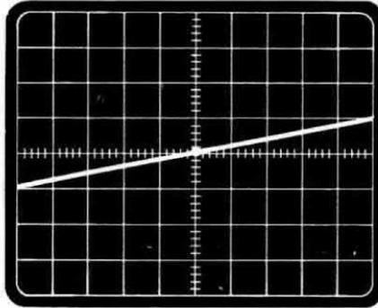
Fig. 3 Predisponendo il tracciacurve per la «calibrazione», sull'oscilloscopio vi apparirà una traccia a linea retta che potrà assumere inclinazioni diverse, vedi fig. 3 e fig. 4. Agendo sui comandi dell'oscilloscopio cercate di portare questa traccia al centro dello schermo.
