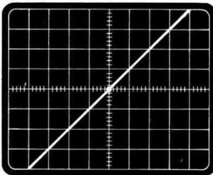
Fig. 5 Posizionata la traccia al centro, ruotate ora il potenziometro «calibrazione» del tracciacurve finché essa non risulterà esattamente a 45° gradi. Notare come la traccia passi esattamente sulla diagonale di ogni quadretto.
