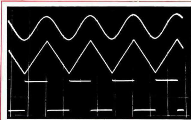
Fig. 4 Come è possibile vedere da questo fotogramma, in uscita dal nostro generatore possiamo prelevare le tre seguenti onde - sinusoidali - triangolari - quadre. A nostro piacimento potremo poi sweepare queste tre onde (vedi fig. 12) o ottenere dei treni d'onda, come visibile in fig. 15.
