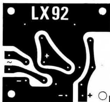
Fig. 9 Circuito stampato a grandezza naturale dell'alimentatore e relativa serigrafia riportata sullo stesso circuito.
