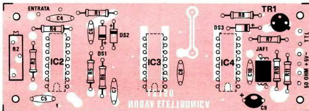
Fig. 10 Anche sul circuito stampato del prescaler troverete il disegno serigrafico dei componenti, che qui riportiamo per rendere ancor più agevole il montaggio al lettore. Si notino nel disegno le tacche di riferimento degli integrati, la polarità dei diodi, il punto di colore del condensatore al tantalio C9 e i terminali di entrata e di uscita.
