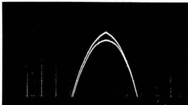
Fig. 10 Se in fase di taratura non si regolano bene i due trimmer R30-R32 la curvatura dell'onda sinusoidale non risulterà perfetta, ma molto appuntita come vedesi in figura.
