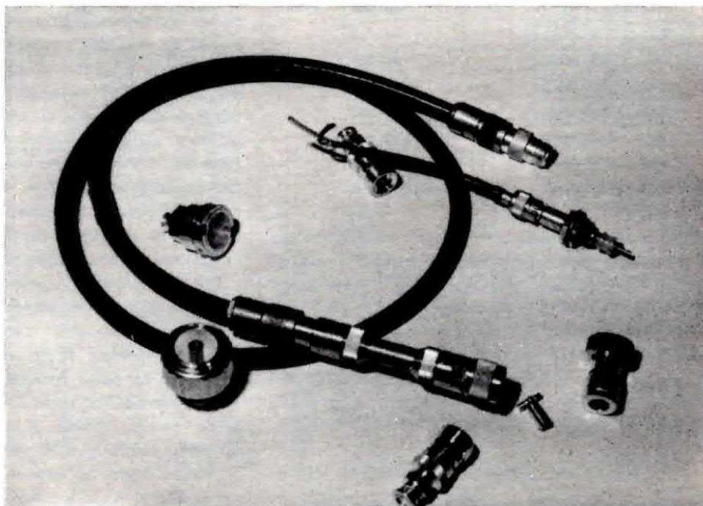
**Fig. 2** Anche impiegando cavi coassiali e bocchettoni UHF a basse perdite è difficile superare i 600 MHz, quindi il lettore non si illuda di superare tale limite. Noi assicuriamo invece che in condizioni normali, la frequenza dei 500 MHz e forse anche i 550, potrà sempre essere raggiunta.
