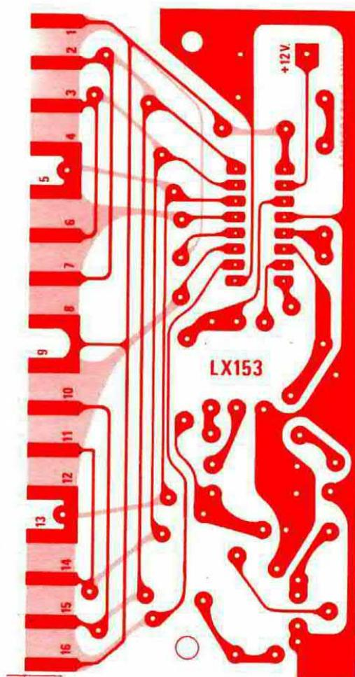
**Fig. 2** Circuito stampato a doppia faccia in grandezza naturale necessario per la realizzazione di questo progetto.
