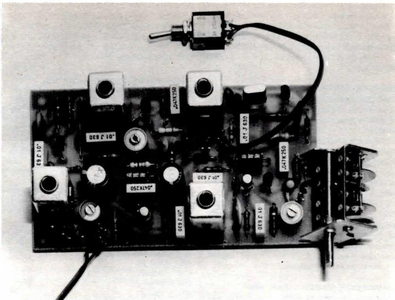
Il V.F.O. a realizzazione ultimata si presenterà come questo nostro prototipo. Si noti come è stato fissato lateralmente sul circuito stampato il condensatore variabile.
