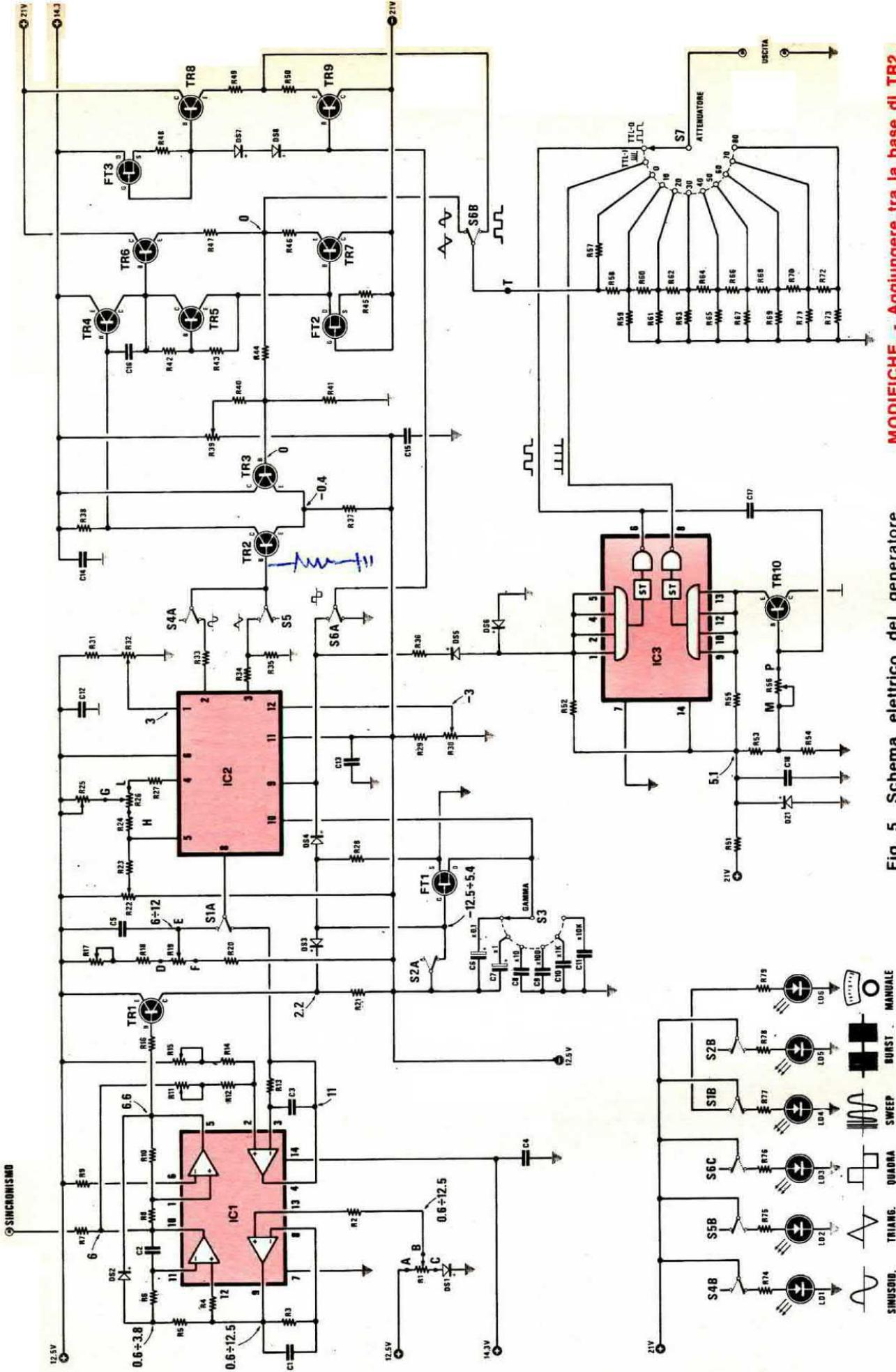
Fig. 5 Schema elettrico del generatore. Lo stadio alimentatore è visibile in fig. 6.
