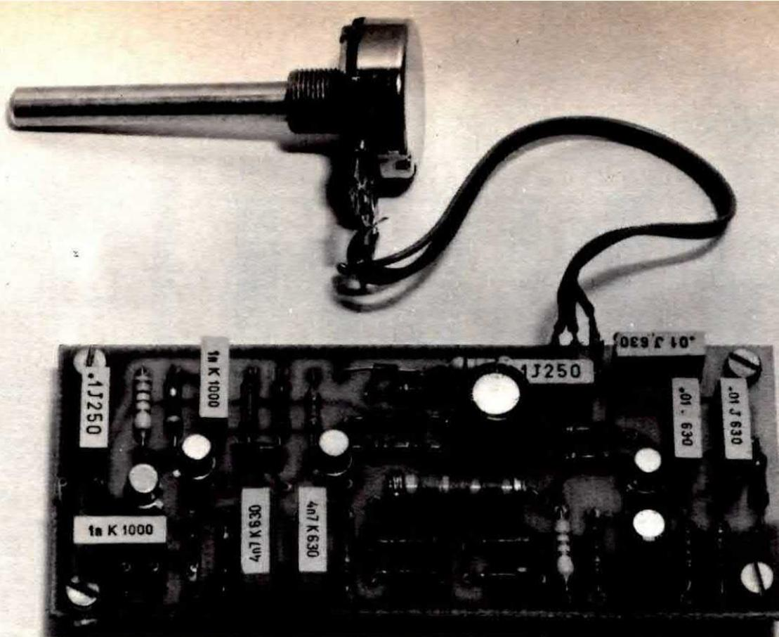
La mancanza di un generatore in FM all'interno di un laboratorio può a volte significare un aumento del tempo necessario per le riparazioni se non addirittura pregiudicare le riparazioni stesse, in quanto non potendo controllare la taratura delle MF, si preferisce non toccarle per non correre il rischio di stararle.
