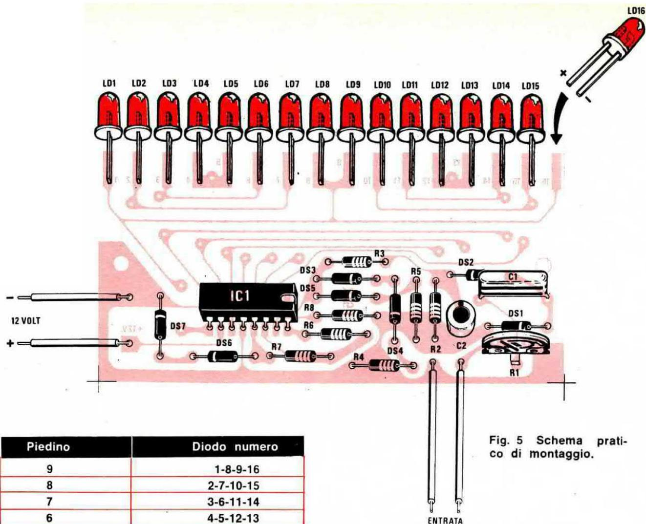
Fig. 5 Schema pratico di montaggio.
