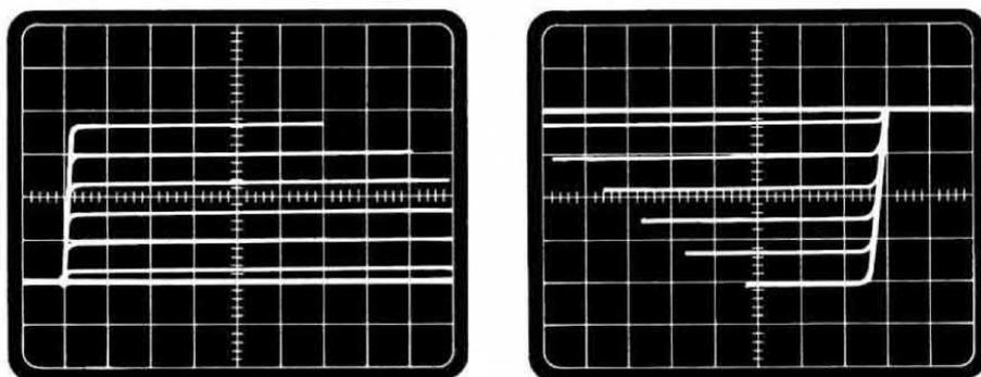
Fig. 10-11 Ottenute le curve indicate nelle figg. 6-7, dovremo ora agire sulle manopole «spostamento traccia» dell'oscilloscopio in modo da far rientrare tutte le curve sullo schermo ottenendo quindi una totale visione delle stesse.
