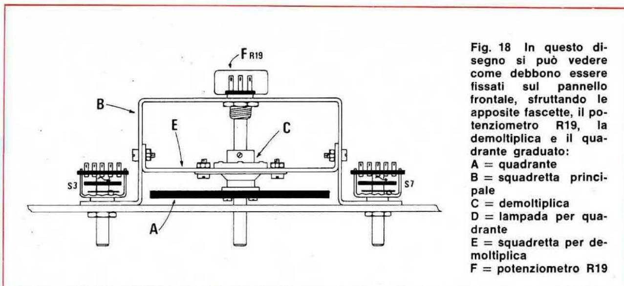
Fig. 18 In questo disegno si può vedere come debbono essere fissati sul pannello frontale, sfruttando le apposite fascette, il potenziometro R19, la demoltiplica e il quadrante graduato:
