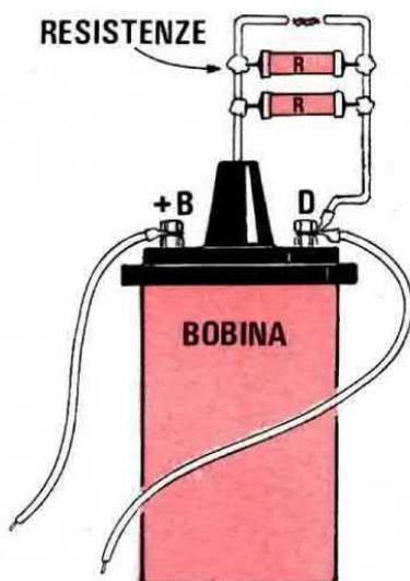
**Fig. 5** È possibile stabilire l'efficacia di un'accensione misurandone il « fattore di utilità », cioè avvicinando a circa 4 millimetri i due elettrodi di scarica ed applicando tra questi delle resistenze in parallelo fino a trovare quel valore in corrispondenza del quale la scintilla non riuscirà più a scoccare. Minore è il valore di questa resistenza, migliore risulterà l'accensione.
