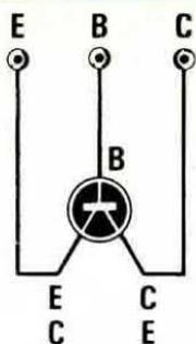
Fig. 29 Per individuare i tre terminali E-B-C di un transistor « sconosciuto », posto il tracciacurve in posizione « tracciacurve », applicheremo nelle varie combinazioni i tre terminali alle boccole E-B-C fino a quando non apparirà sullo schermo una traccia simile a quella di figg. 10-11. Così facendo avremo solo individuato il terminale di BASE e non gli altri due.
