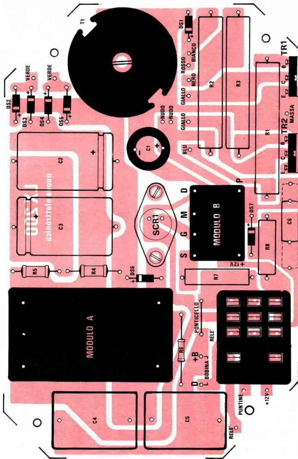
Fig. 2 Circuito stampato a grandezza naturale e relativo disegno serigrafico che agevolerà notevolmente il lettore nella realizzazione pratica. Si noti che tra lo zoccolo del relè e il modulo A (vicino a R6) è necessario effettuare un ponticello con filo di rame. A destra vicino alla resistenza R2, i fori contraddistinti dai nomi dei vari colori sono quelli in cui dovremo inserire i fili del trasformatore T1.
