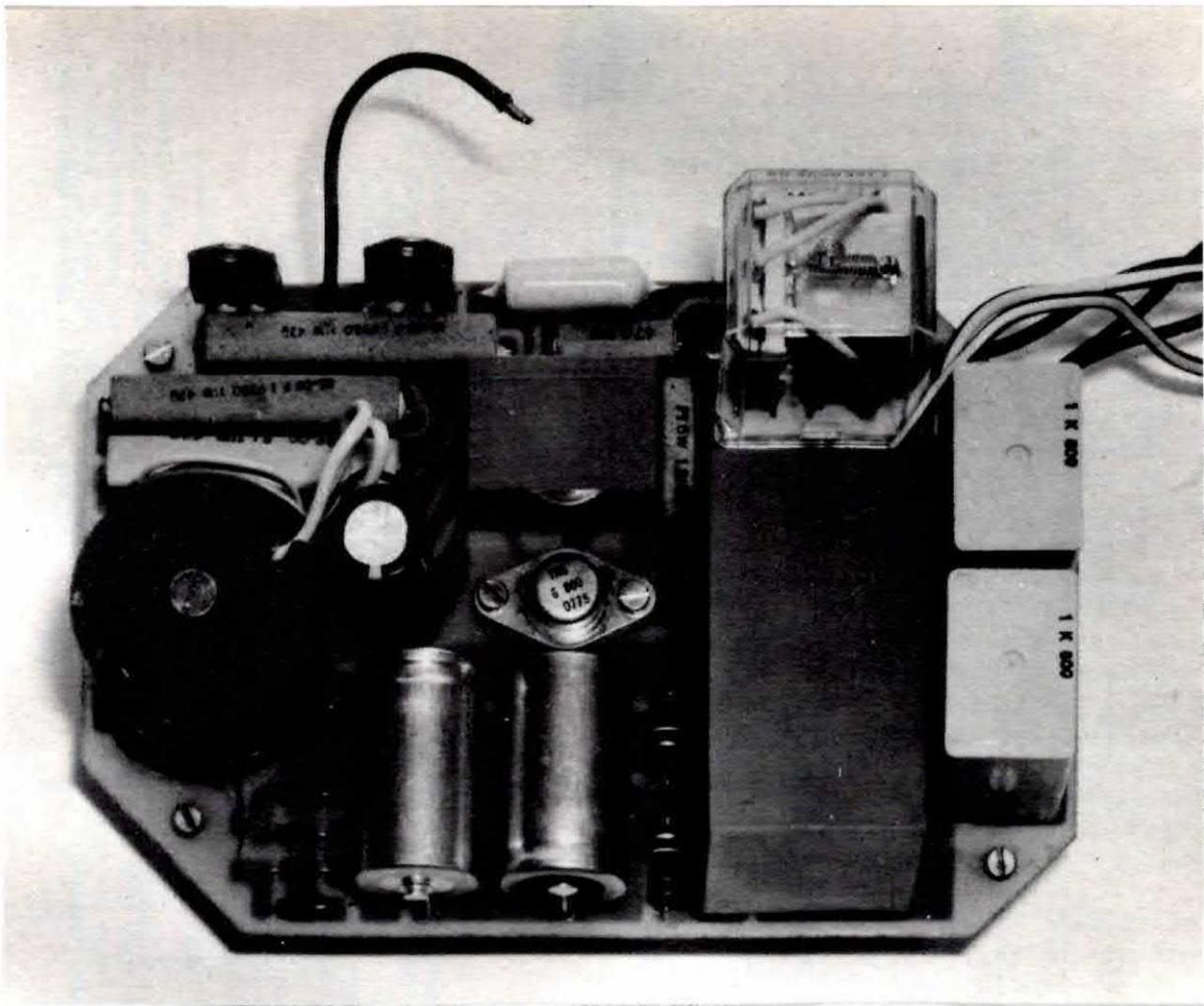
Nella foto potete osservare come si presenta l'accensione catodica tipo sport una volta montati tutti i componenti sul circuito stampato. Si notino in alto a sinistra i due transistor TIP.3055 del convertitore e il filo di massa che dovrà risultare collegato alla carcassa metallica del contenitore.
