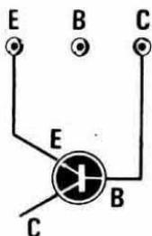
Fig. 26 Per conoscere la caduta di tensione introdotta da un transistor o per rilevare se questo è un «germanio» o un «silicio» dovremo collegarlo al tracciacurve come indicato in disegno. Sullo schermo apparirà questa traccia la quale ci rivelerà tutti quei dati che a noi interessano. Il punto luminoso posto quasi all'estremità dell'onda in salita, servirà come riferimento.
