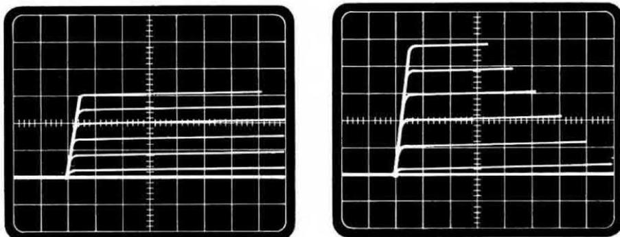
Se le curve apparissero talmente ravvicinate da confondersi l'una con l'altra, dovrete agire sul commutatore centrale a 11 posizioni, ruotandolo gradatamente in senso orario (cioè aumentando per gradi la corrente da mandare in base al transistor, dai 0,01 milliamper iniziali, a 0,02 mA o a 0,05 mA oppure a 0,08) finché non riuscirete ad ottenere sullo schermo 6 curve sufficientemente distanziate, vedi fig. 12-13.
