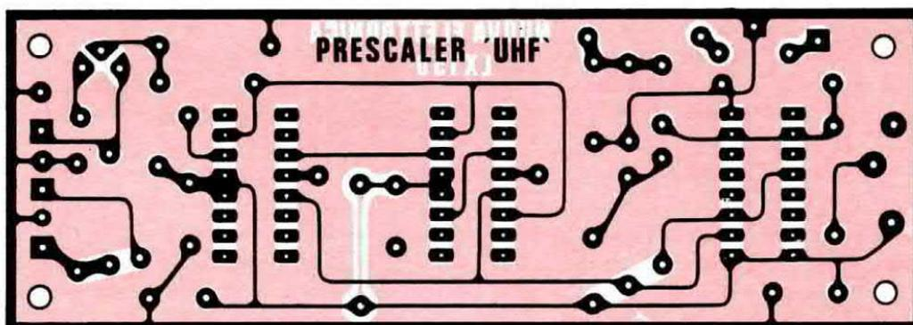
Fig. 6 Disegno a grandezza naturale del circuito stampato necessario per la realizzazione di questo prescaler. Tale circuito a doppia faccia è stato studiato per limitare le perdite UHF onde poter raggiungere e superare i 500 MHz.
