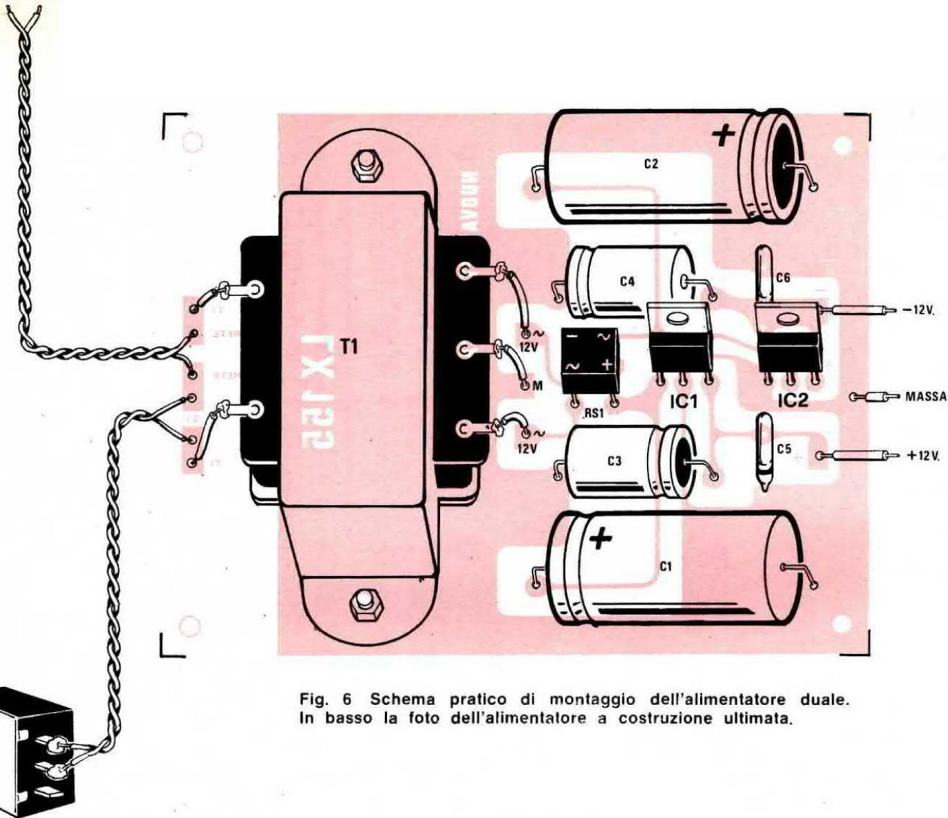
Fig. 6 Schema pratico di montaggio dell'alimentatore duale. In basso la foto dell'alimentatore a costruzione ultimata.
