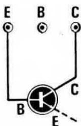
Fig. 31 Se alla boccola C anziché il terminale « collettore » avessimo collegato l'« emettitore » sullo schermo dell'oscilloscopio sarebbe apparsa questa traccia, cortissima rispetto alla precedente e quindi ben distinguibile da essa (vedi fig. 30).
