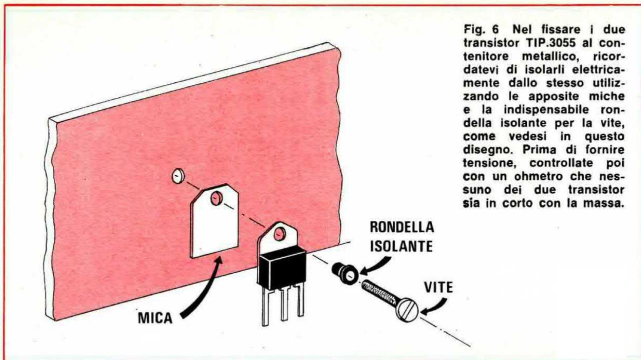
Fig. 6 Nel fissare i due transistor TIP.3055 al contenitore metallico, ricordatevi di isolarli elettricamente dallo stesso utilizzando le apposite miche e la indispensabile rondella isolante per la vite, come vedesi in questo disegno. Prima di fornire tensione, controllate poi con un ohmetro che nessuno dei due transistor sia in corto con la massa.
