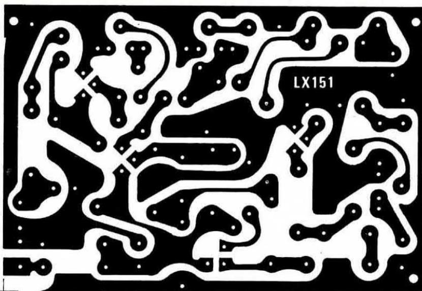
**Fig. 2** Circuito stampato a grandezza naturale necessario alla realizzazione di questo compressore.
