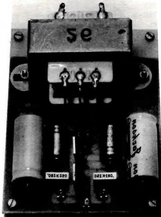
Se desideriamo ottenere un amplificatore perfettamente silenzioso, eliminando cioè ogni possibile fonte di ronzio, dovremo porre una certa attenzione nell'eseguire i collegamenti fra il circuito stampato e i potenziometri di volume, i commutatori e i terminali d'ingresso utilizzando per questo scopo del cavetto schermato la cui calza metallica dovrà essere collegata al terminale di massa dello stampato.
