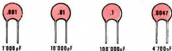
Nei condensatori, quando il valore è preceduto da un « punto », ad esempio .001 oppure .1 o .0047, occorre leggerli sempre come se prima del punto esistesse uno 0, cioè 0,001 - 0,1 - 0,0047 mF. che convertiti in pF, risulteranno 1.000 pF 100.000 pF e 4.700 pF.
