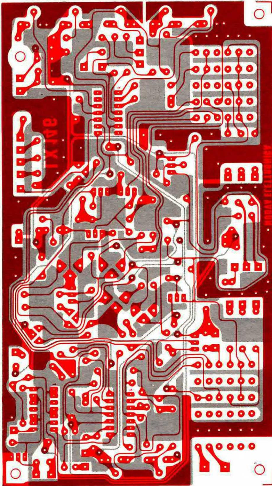
Fig. 9 Circuito stampato a grandezza naturale utile per la realizzazione del generatore di funzioni. Come è possibile constatare, questo circuito (siglato LX 146) risulta a doppia faccia, quindi i fori che presentano un bollino di rame su entrambe le facce (superiore ed inferiore) servono per inserire dei fili di rame necessari a cortocircuitare le due piste in modo che risultino elettricamente collegate.
