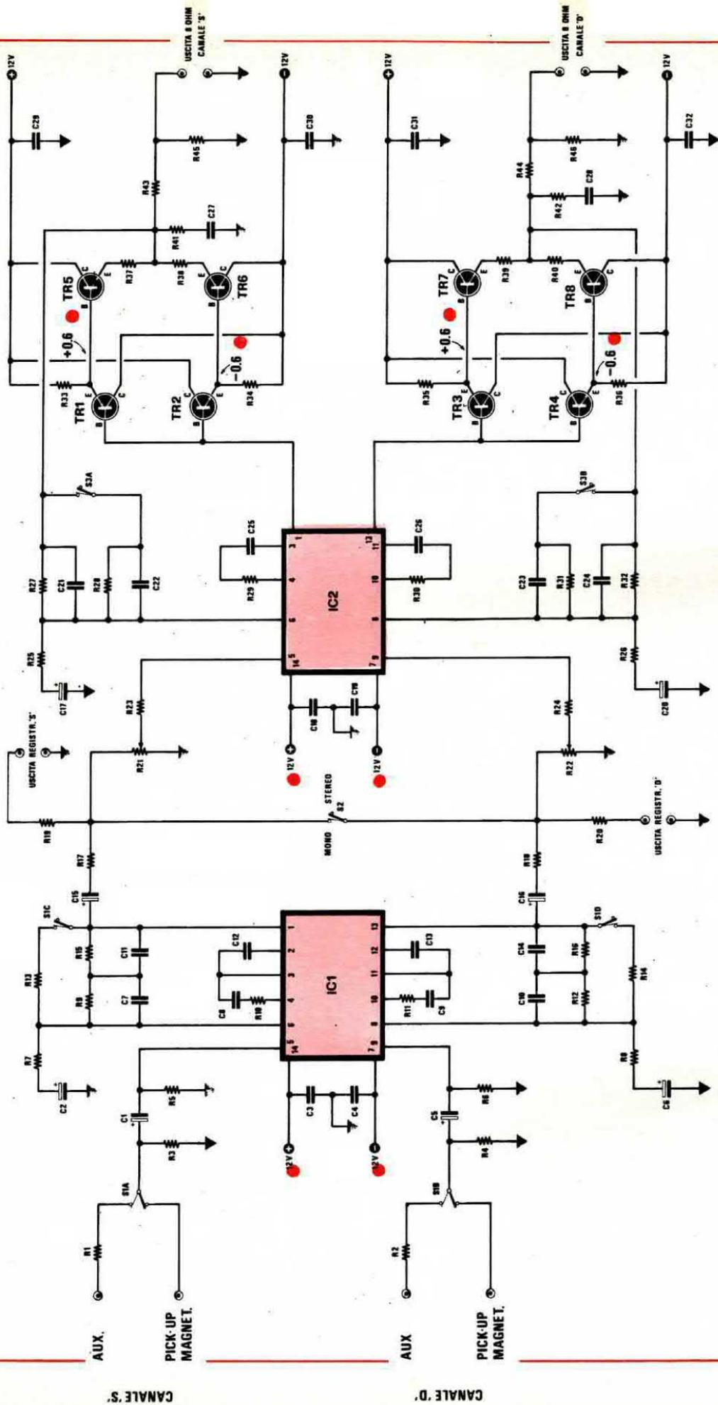
Fig. 1 Schema elettrico completo dell'amplificatore HI-FI stereo per cuffia. A sinistra le connessioni dei transistor e dell'integrato SN76131.
