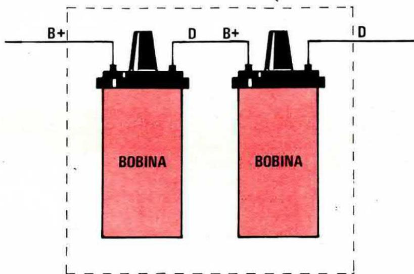
**Fig. 7** Nelle auto bicilindriche in cui si impiegano due bobine in serie è possibile installare l'accensione considerando le stesse come se fossero una sola. Prima di effettuare questo collegamento però, controllate che non esista tra i vari terminali delle bobine e la massa alcun condensatore (sempre presente se possedete l'autoradio) e se esiste, dovrete prima toglierlo.
