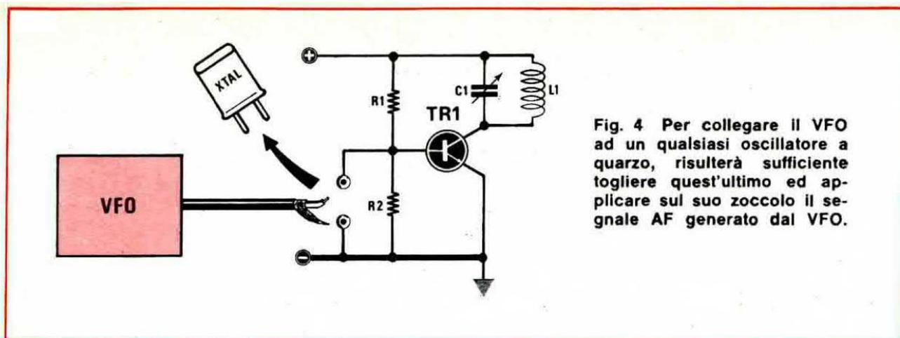
Fig. 4 Per collegare il VFO ad un qualsiasi oscillatore a quarzo, risulterà sufficiente togliere quest'ultimo ed applicare sul suo zoccolo il segnale AF generato dal VFO.
