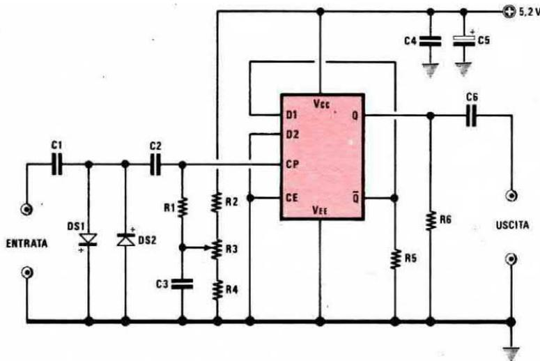
Fig. 1 Lo schema che la Casa Costruttrice consiglia per l'11C06 visibile in figura è solo uno schema base al quale è necessario apportare sostanziali modifiche pratiche per poterlo accoppiare a integrati TTL o ECL.
