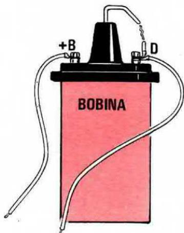
**Fig. 4** Un'ottima accensione elettronica deve essere in grado di produrre scintille della lunghezza di almeno 3-4 centimetri. Tale prova comunque non è sufficiente a dimostrare che l'accensione dispone della potenza richiesta dal vostro motore, come abbiamo esaurientemente spiegato nell'articolo.
