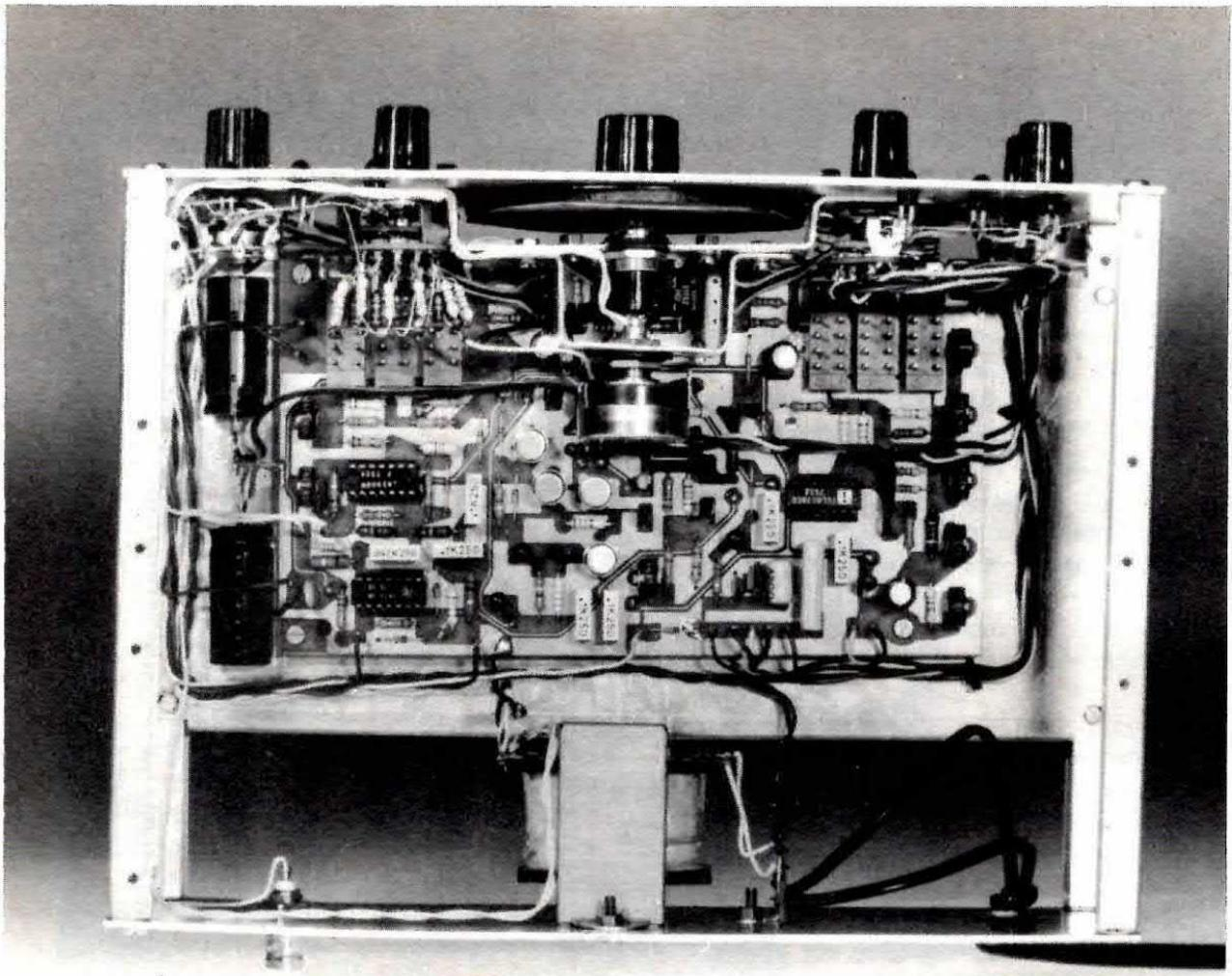
il solo trasformatore) direttamente sul circuito stampato in modo da semplificare al massimo il montaggio.
