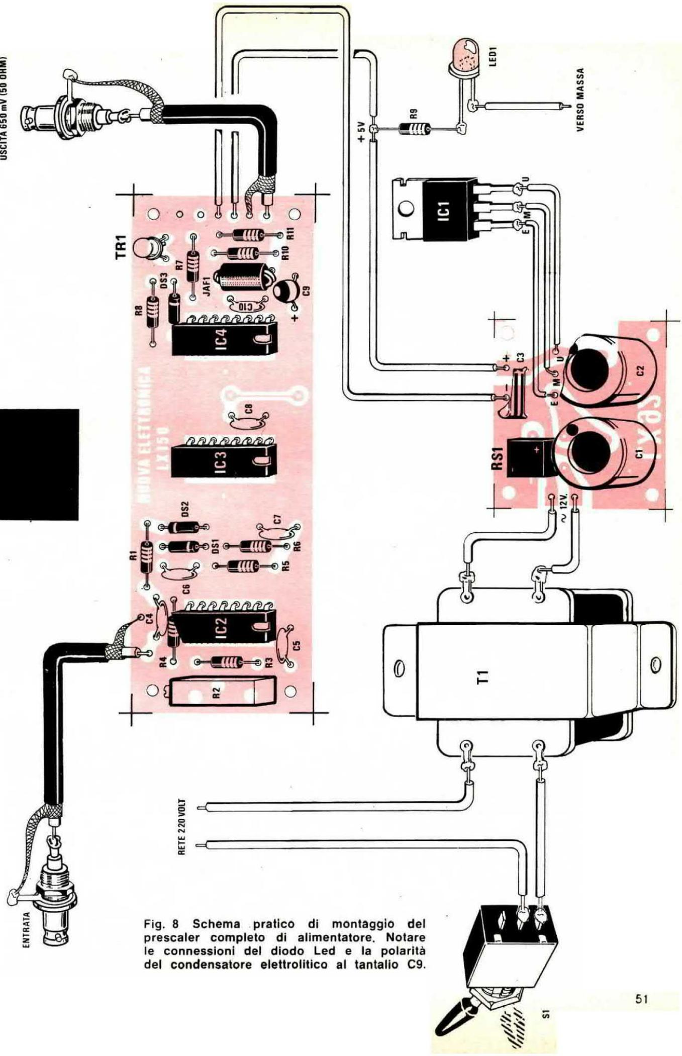
Fig. 8 Schema pratico di montaggio del prescaler completo di alimentatore. Notare le connessioni del diodo Led e la polarità del condensatore elettrolitico al tantalio C9.
