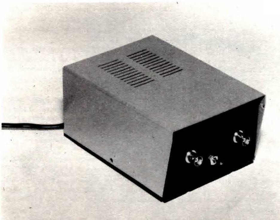
Come si presenta a realizzazione ultimata il prescaler da 500 MHz. Come vedesi nella figura in alto a sinistra, l'uscita del prescaler dovrà essere semplicemente collegata all'entrata AF-VHF di un qualsiasi frequenzimetro in grado di misurare almeno 50 MHz.
