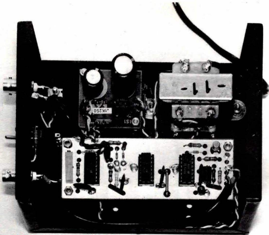
Tutto questo non solo è stato da noi tenuto nella massima considerazione, ma abbiamo pure prevista un'uscita compatibile con ingressi TTL onde permettere l'utilizzazione del prescaler con frequenzimetri sprovvisti di ingresso VHF a 52 ohm.
