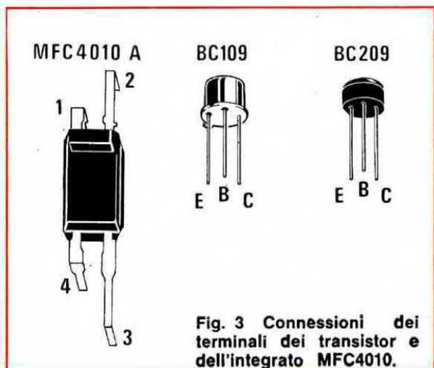
**Fig. 3** Connessioni dei terminali dei transistor e dell'integrato MFC4010.
