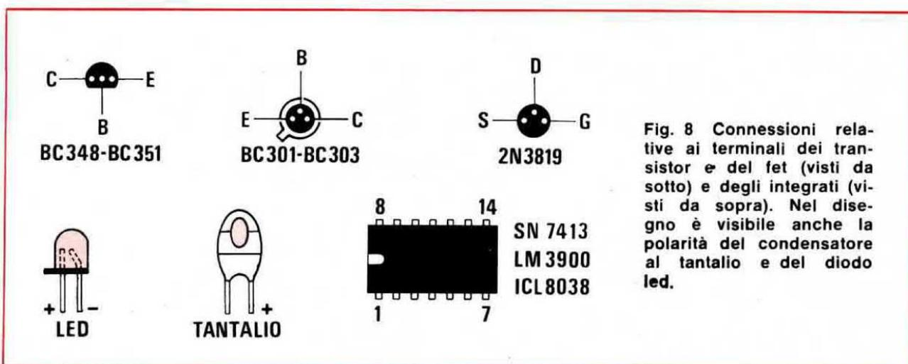
Fig. 8 Connessioni relative ai terminali dei transistor e del fet (visti da sotto) e degli integrati (visti da sopra). Nel disegno è visibile anche la polarità del condensatore al tantalio e del diodo led.
