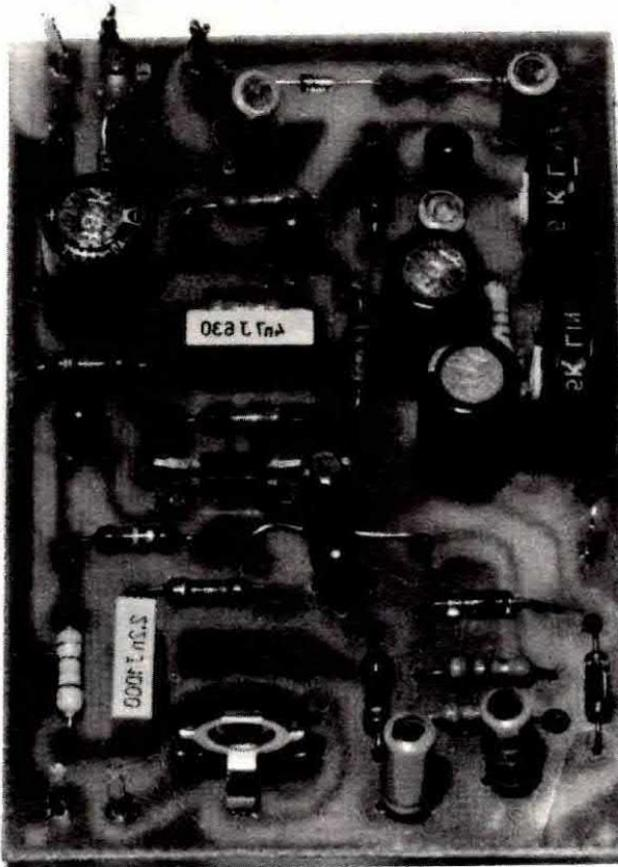
Fig. 5 A costruzione ultimata il vostro compressore si presenterà come questa foto. Si noti al centro l'integrato MFC.4010.
