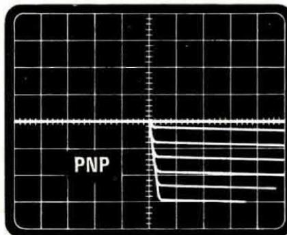
Fig. 8-9 Su taluni oscilloscopi le tracce, anziché presentarsi come indicato nelle figg. 6-7, possono risultare rovesciate (come se fossero viste allo specchio): comunque per i transistor NPN saranno sempre poste sopra la metà dello schermo e per gli NPN sotto.
