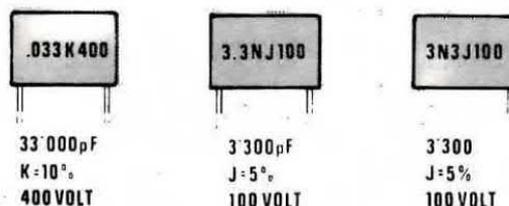
Fig. 4 Sempre nei condensatori poliestere possiamo rilevare i più disparati sistemi di indicazioni, facili a leggerle solo conoscendone la regola. Nel primo a sinistra si usa il « punto » .033 = 0,033 mF — nel secondo 3n3 = 3,3 nanofarad = 3.300 pF — nel terzo 3,3 n = 3,3 nanofarad = 3.300 pF. Le altre indicazioni K o J indicano la tolleranza il K = 10% ed il J = 5%. Il terzo valore 400 oppure 100 o 250 è infine la massima tensione di lavoro.
