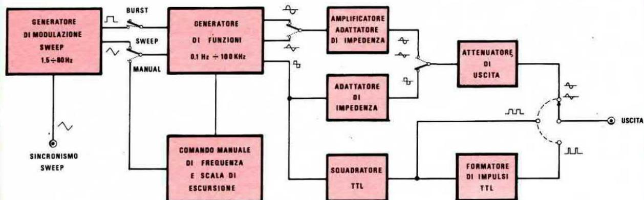
Fig. 3 Schema a blocchi del « generatore di funzioni ». Da questo schema si possono meglio comprendere le finalità dei singoli stadi presenti in tale circuito.
