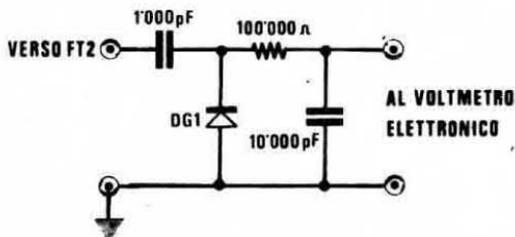
Fig. 2 Per controllare l'ampiezza del segnale AF generato dall'oscillatore locale potremo utilizzare la sonda qui rappresentata. Come diodo rivelatore dovremo impiegare uno esclusivamente al « germanio » e come strumento di misura solo un voltmetro elettronico.
