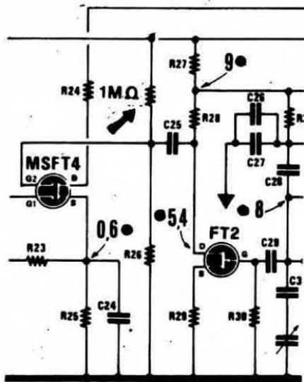
Fig. 1 Se il ricevitore « bigamma » presenta una scarsa sensibilità sulla sola gamma dei 144 MHz, come accennato in questa errata corregge, il difetto è causato esclusivamente dallo stadio oscillatore. Per aumentare la sensibilità, oltre ad aumentare la capacità dei condensatori indicati nell'articolo, si potrà inserire tra il G2 (del mosfet 4) ed il positivo di alimentazione, una resistenza da 1 megaohm come visibile in disegno.
