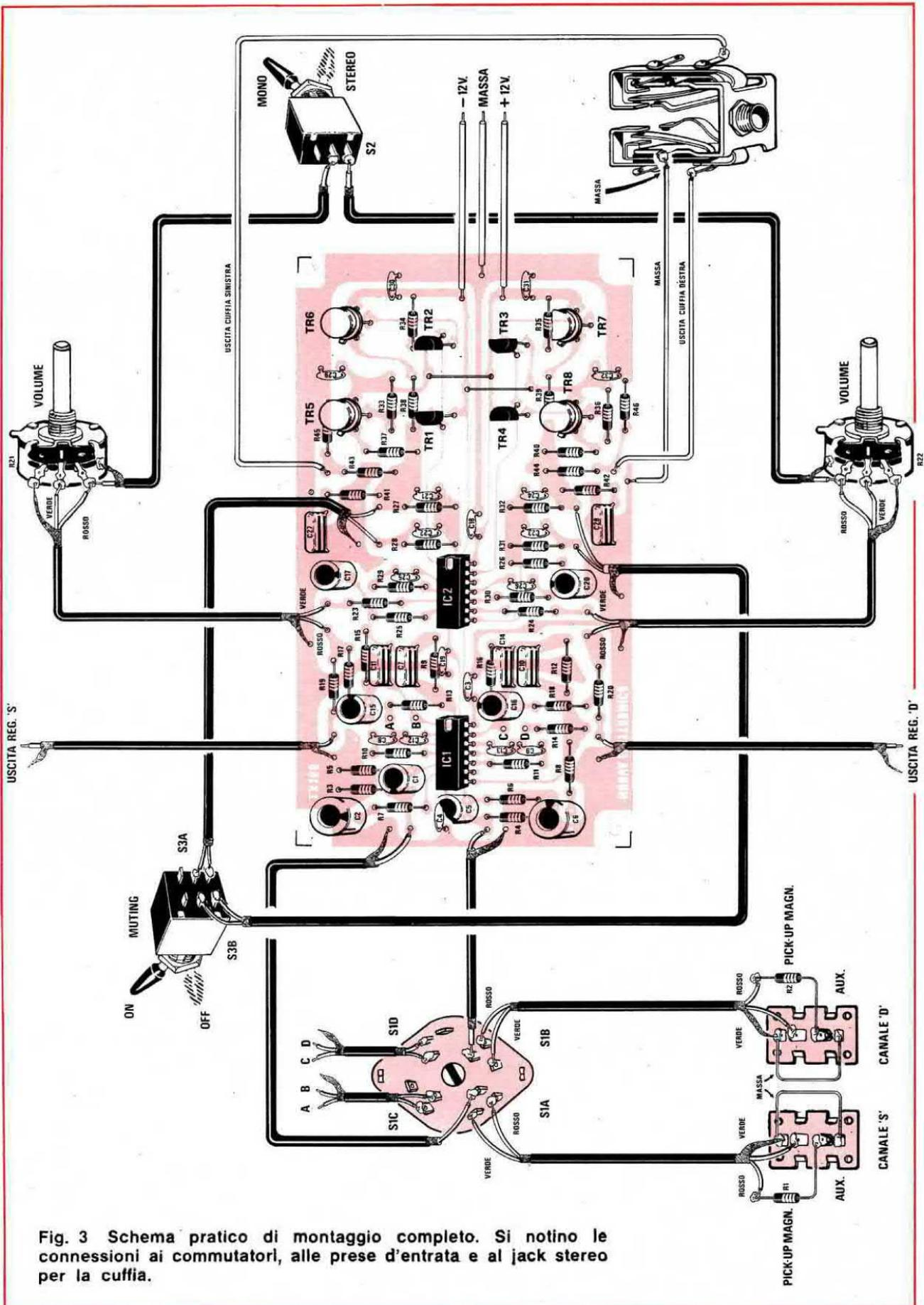
Fig. 3 Schema pratico di montaggio completo. Si notino le connessioni ai commutatori, alle prese d'entrata e al jack stereo per la cuffia.
