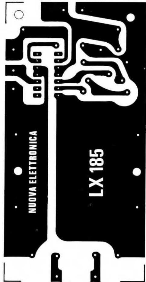
Fig. 30 Circuito stampato dell'alimentatore del visualizzatore.
