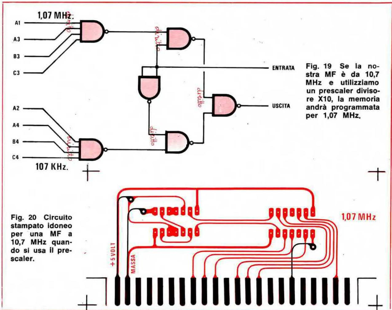
Fig. 20 Circuito stampato idoneo per una MF a 10,7 MHz quando si usa il prescaler.
