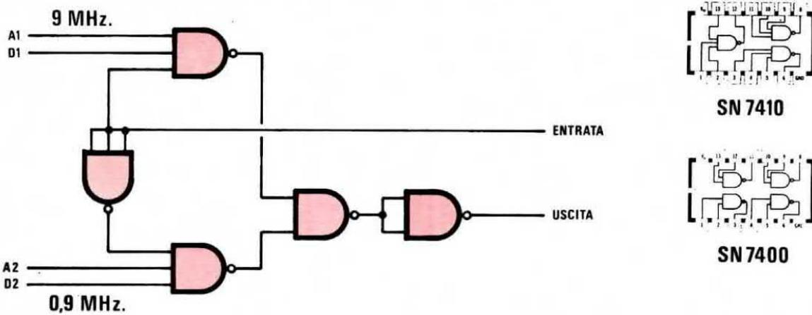
Fig. 11 Schema elettrico della memoria per MF a 9 MHz. I numeri presenti sulle entrate dei nand (vedi a sinistra) debbono collegarsi alle corrispondenti uscite degli integrati divisori visibili in fig. 7. La scheda di fig. 12 è realizzata per ottenere appunto tale connessione.
