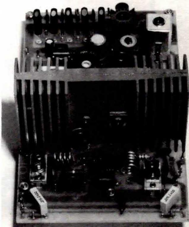
Foto del trasmettitore visto dal lato opposto al precedente. Si notino in basso i due condensatori (posti obliquamente sullo stampato) e la resistenza relativi al misuratore di SWR.
