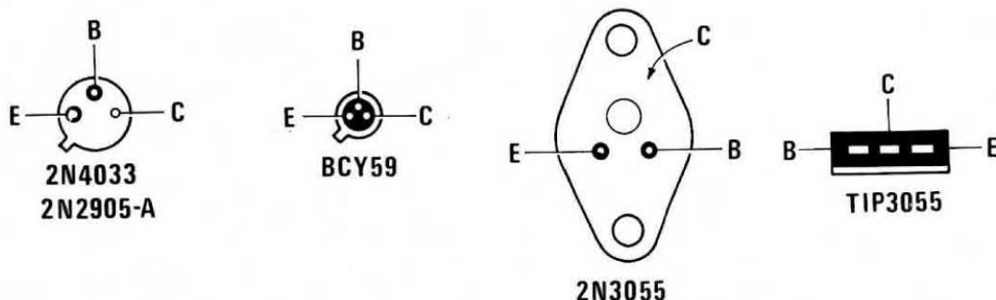
**Fig. 1** Connessioni dei terminali dei transistor impiegati in questo alimentatore. Il transistor TR3 (un TIP3055) può essere tranquillamente sostituito con un 2N3055 o qualsiasi altro transistor di potenza ad esso equivalente.
