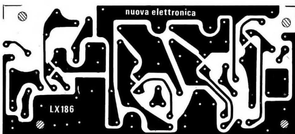
Fig. 8 Circuito stampato del preamplificatore.
