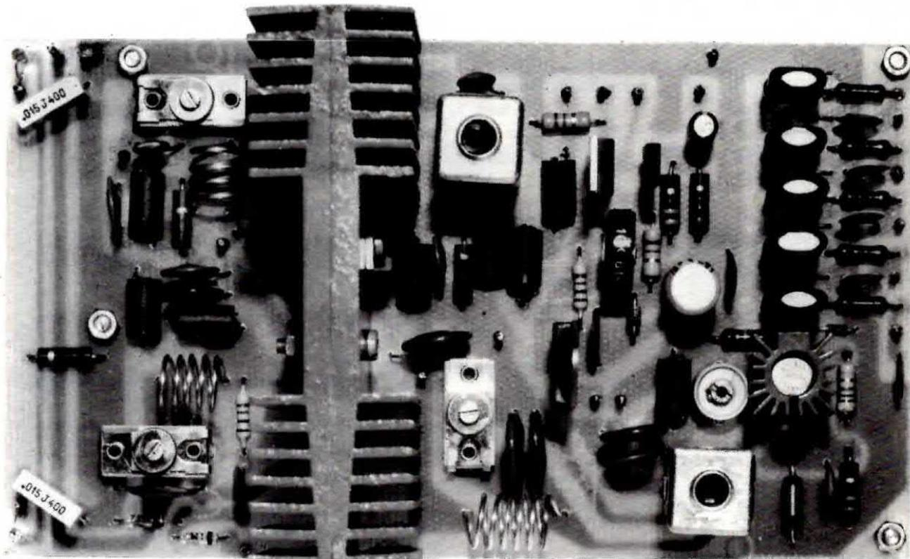
Foto del trasmettitore TX21. L'aletta di raffreddamento sulla quale fissaremo (senza isolarli) i due transistor TR7-TR8, anche se nella foto può sembrare una sola, in pratica è costituita da due elementi distinti posti uno accanto all'altro e tenuti assieme dalle viti di fissaggio dei transistor.
