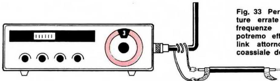
**Fig. 33** Per evitare letture errate dovute a frequenze armoniche potremo effettuare un link attorno al cavo coassiale del TX.
