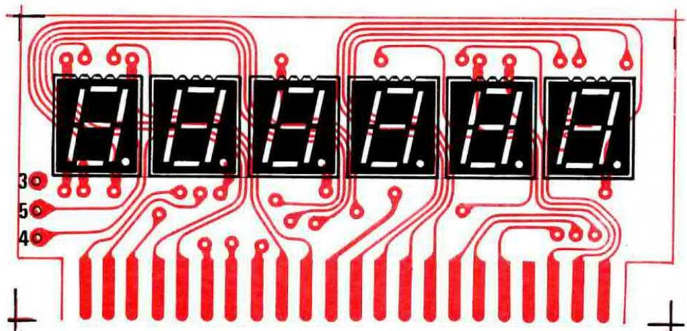
**Fig. 5** Per ottenere lo spostamento automatico del punto, dovremo collegare i terminali 1-2 del circuito stampato LX180/A ai terminali 3-4 della scheda LX180/B.
