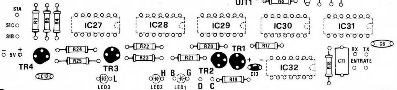
Fig. 1 Sul circuito stampato LX180/A il lettore troverà riportato questo disegno serigrafico utile per individuare l'ubicazione dei diversi componenti. **NOTA IMPORTANTE.** Sulla destra sono invertite le scritte ENTRATA RX e ENTRATA TX quindi occorre applicare il segnale del TX dove è scritto RX e viceversa.
