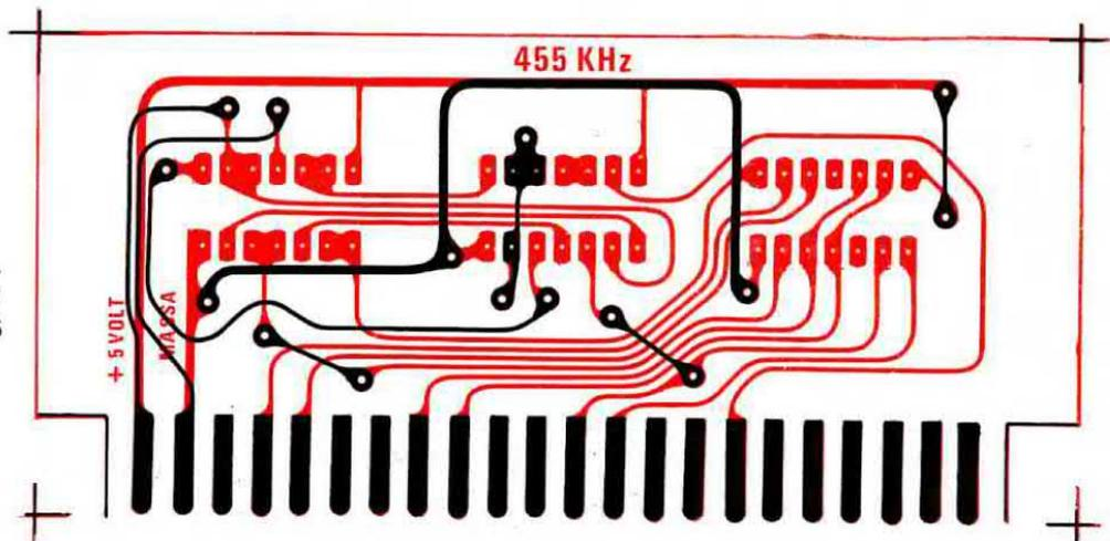
Fig. 10 Schema pratico di montaggio della MF a 455 KHz.
