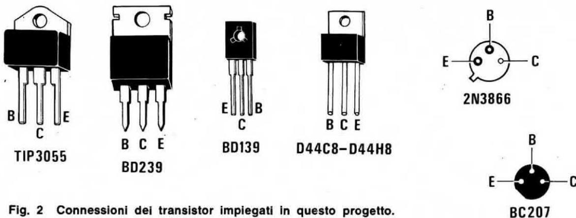
Fig. 2 Connessioni dei transistor impiegati in questo progetto.
