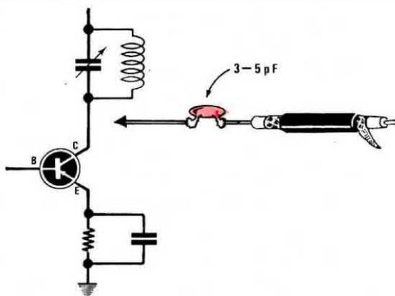
la bobina oscillatrice, (in particolar modo se non le avvolgerete dal lato freddo) la frequenza dell'oscillatore si modifichi leggermente a causa del carico aggiunto. Questo tuttavia non dovrà preoccuparvi in quanto agendo sul nucleo della bobina e leggendo contemporaneamente la frequenza sul visualizzatore, potrete riportare il tutto alla normalità.
