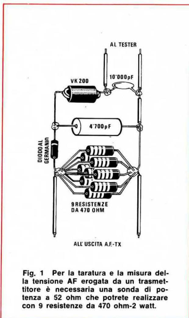
Fig. 1 Per la taratura e la misura della tensione AF erogata da un trasmettitore è necessaria una sonda di potenza a 52 ohm che potrete realizzare con 9 resistenze da 470 ohm-2 watt.
