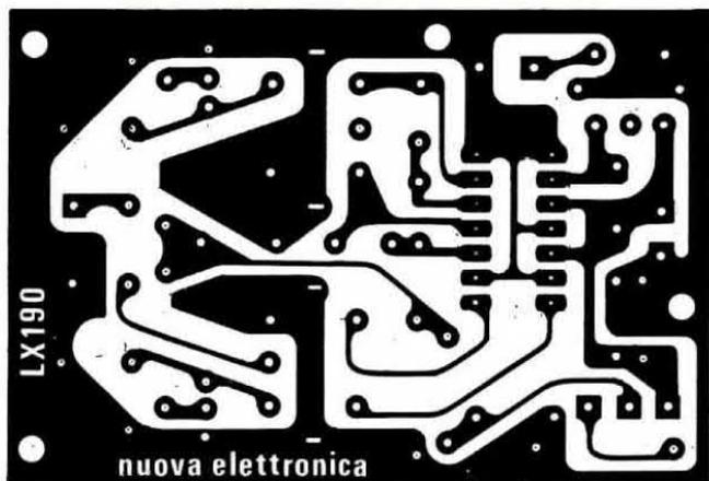
Fig. 3 Circuito stampato a grandezza naturale del convertitore. Su tale circuito il lettore troverà riportato, dal lato componenti, un disegno serigrafico che lo agevolerà nel montaggio.
