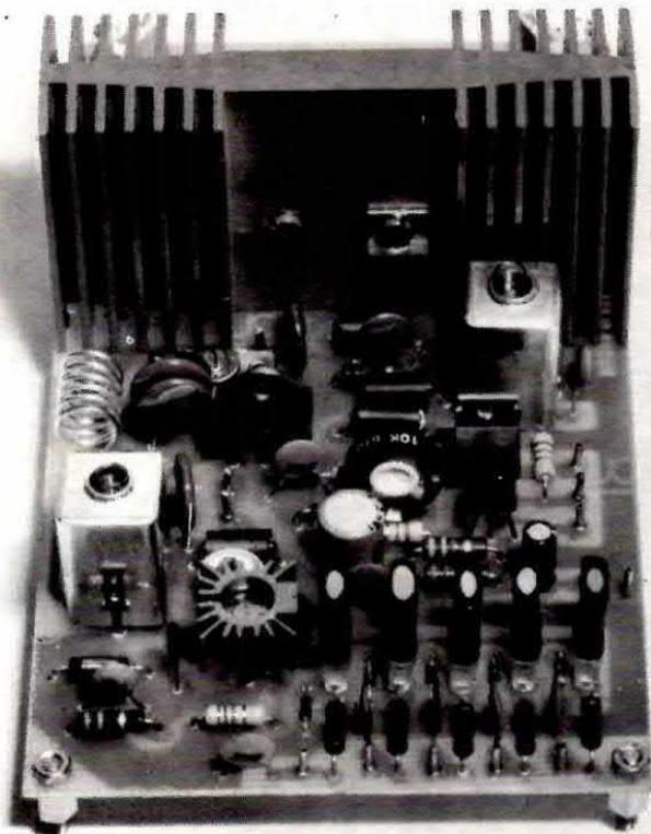
Foto del trasmettitore visto dal lato dei quarzi. Si noti il trimmer R10 (al centro dietro ai quarzi) necessario per regolare la tensione di alimentazione del TX.
