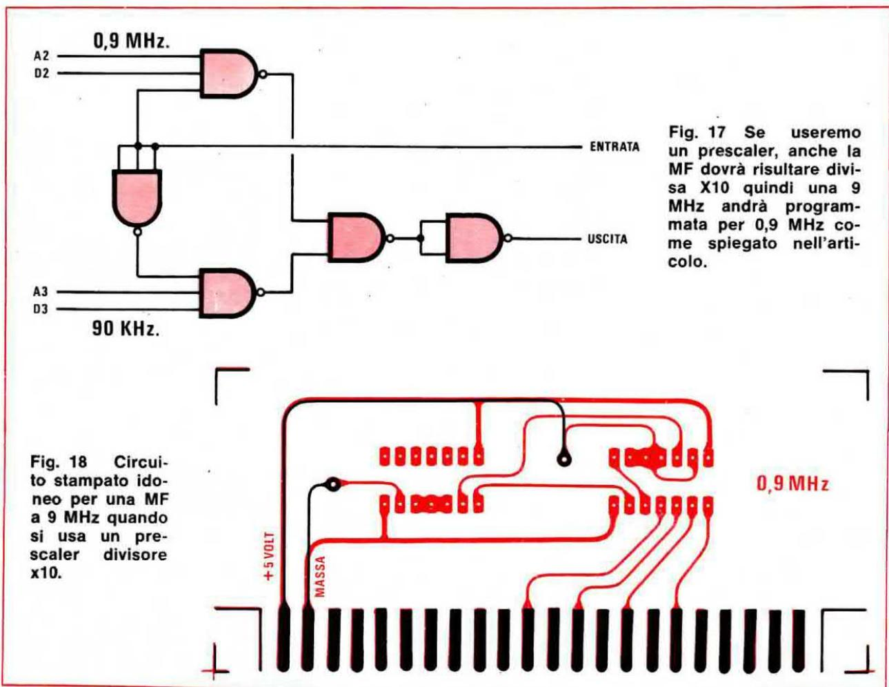
Per far questo saranno necessari un SN7410 composto da 3 NAND a 3 ingressi e un SN7400 composto da 4 NAND a 2 ingressi che troveranno alloggio sul circuito stampato visibile in fig. 18.
