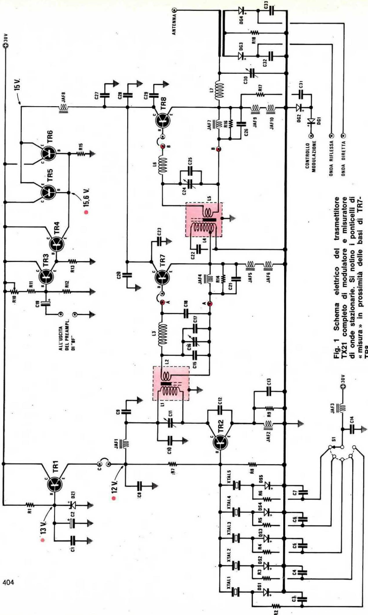
Fig. 1 Schema elettrico del trasmettitore TX21 completo di modulatore e misuratore di onde stazionarie. Si notino i ponticelli di « misura » in prossimità delle basi di TR7-TR8.
