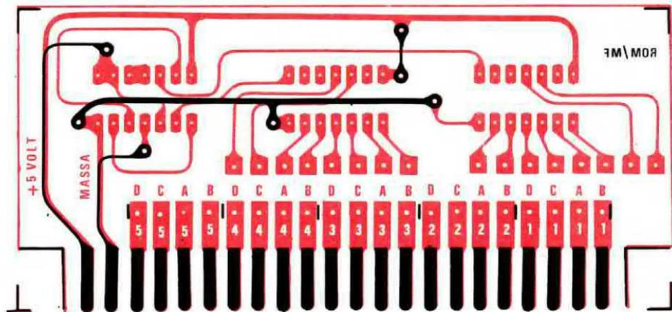
Fig. 23 Schema pratico di montaggio della Rom universale.
