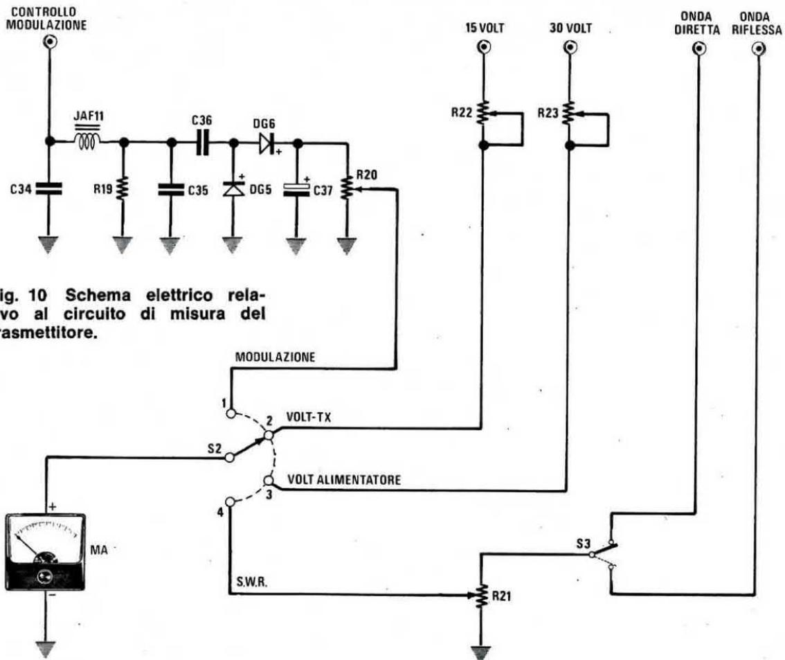
Fig. 10 Schema elettrico relativo al circuito di misura del trasmettitore.
