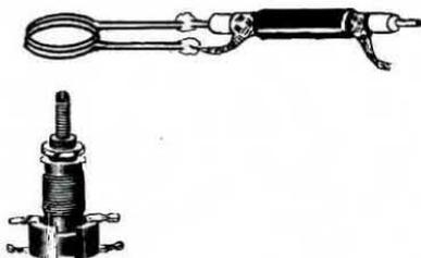
Fig. 34 Più difficile risulta invece prelevare l'alta frequenza dal ricevitore. Se la bobina oscillatrice è facilmente accessibile potremo avvolgere un link composto da una o due spire sul suo supporto.
