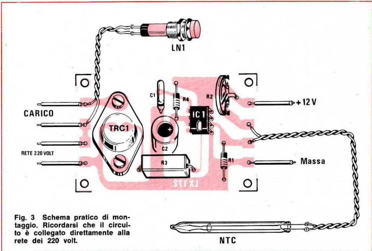
Fig. 3 Schema pratico di montaggio. Ricordarsi che il circuito è collegato direttamente alla rete dei 220 volt.
