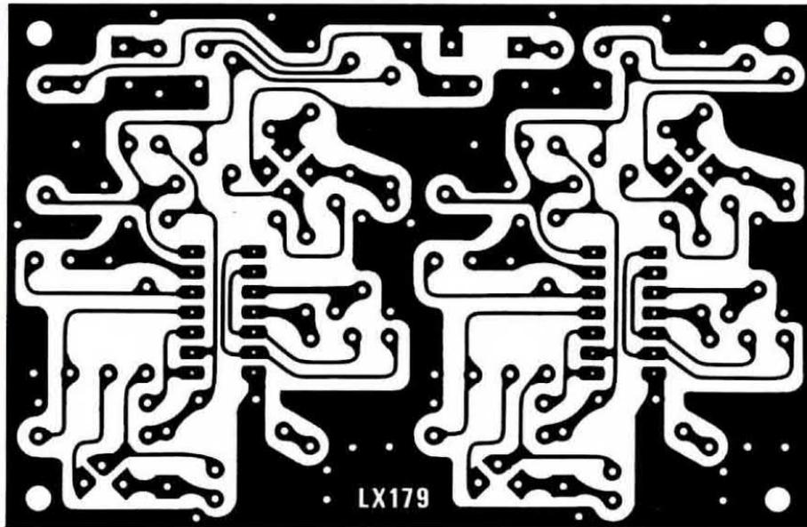
Fig. 27 Circuito stampato idoneo a ricevere il doppio preamplificatore di AF.
