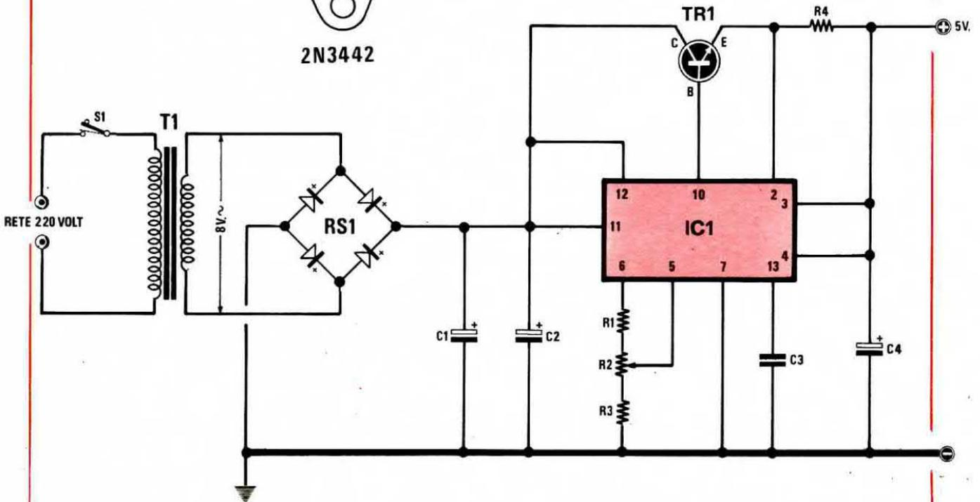
Fig. 31 Schema pratico di montaggio dell'alimentatore. Il transistor TR1 va applicato ad un'aletta di raffreddamento isolandolo elettricamente da essa.
