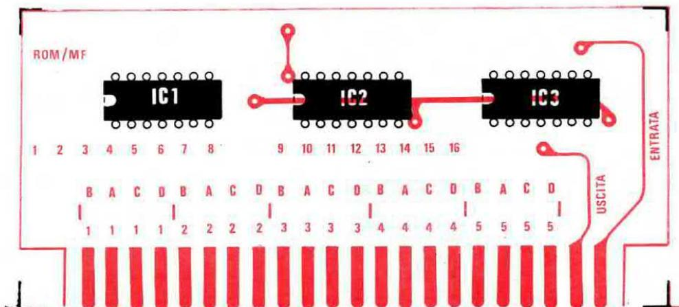
Fig. 24 Se volessimo programmare, con la ROM universale, una MF a 470 KHz, dovremmo effettuare i collegamenti indicati in rosso (leggere articolo).
