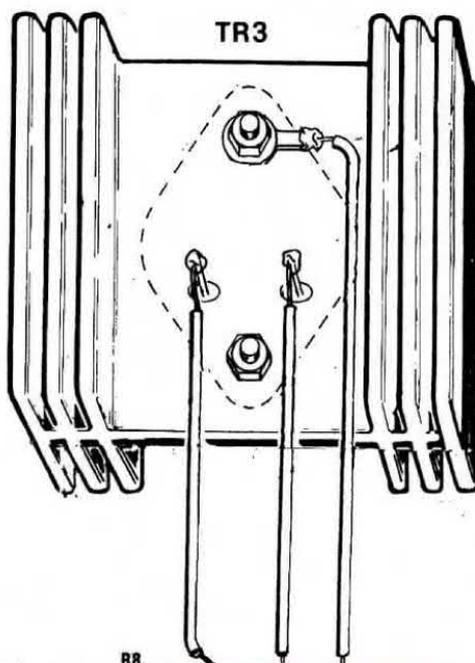
Fig. 4 Schema pratico di montaggio dell'alimentatore. NOTA = Volendo utilizzare questo circuito per il TX21, si consiglia di impiegare, come transistor TR3, un TIP.3055 anziché il 2N3055 in quanto il TIP lo potremo fissare più facilmente (isolandolo con una mica) sotto il piano di alluminio del contenitore oppure sul pannello posteriore della scatola. Tale transistor infatti, nel caso del TX21, non scalda eccessivamente.
