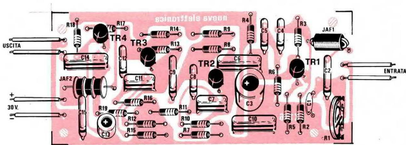
Fig. 9 Realizzazione pratica del preamplificatore.
