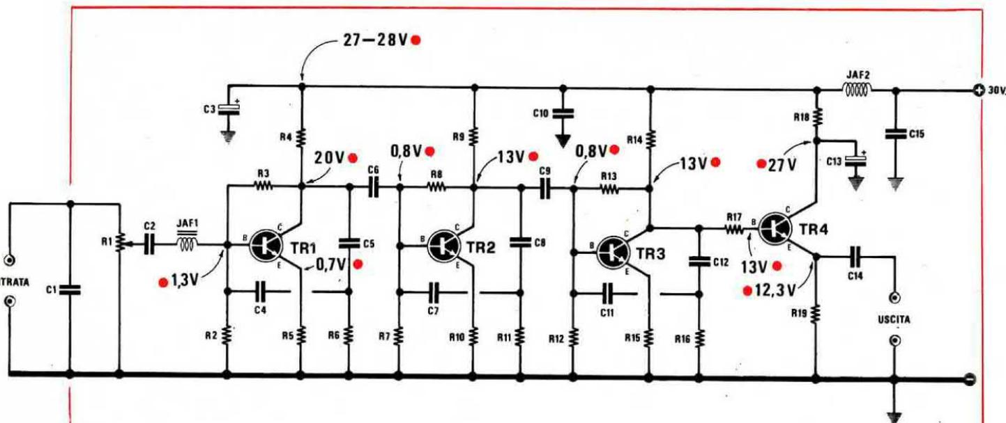
Fig. 3 Schema elettrico del preamplificatore di BF.
