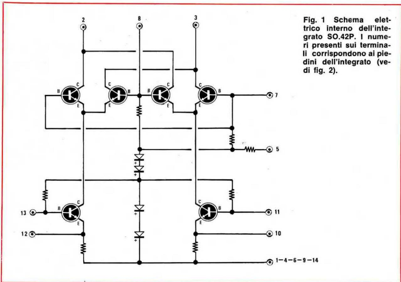
**Fig. 1** Schema elettrico interno dell'integrato SO.42P. I numeri presenti sui terminali corrispondono ai piedini dell'integrato (vedi fig. 2).
