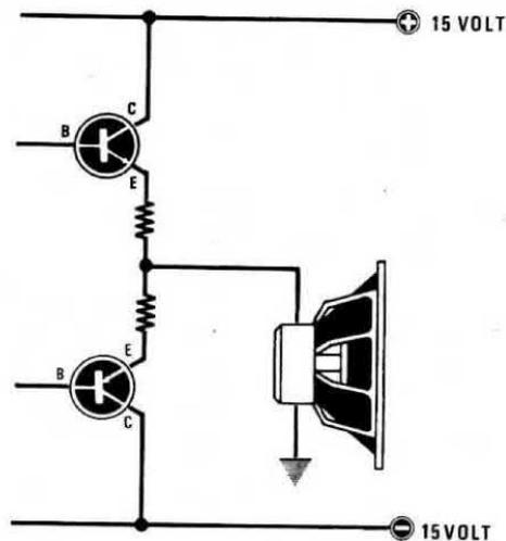
**Fig. 1** Il circuito di protezione per casse acustiche serve solo ed unicamente per gli amplificatori alimentati per tensione duale. In questi amplificatori infatti, se un transistor va in corto, tutta la tensione di alimentazione si riversa sulla bobina mobile dell'altoparlante.
