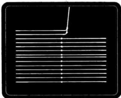
**Fig. 5** Aumentando progressivamente la corrente di gate, raggiungeremo una condizione in cui le ultime righe superiori divergeranno verso l'alto. Tale figura ci conferma che l'SCR si è eccitato; contando le linee orizzontali (partendo dalle due di centro) e moltiplicando la corrente di gate, indicata dalla manopola, per il numero di queste righe, conosceremo la corrente di eccitazione.
