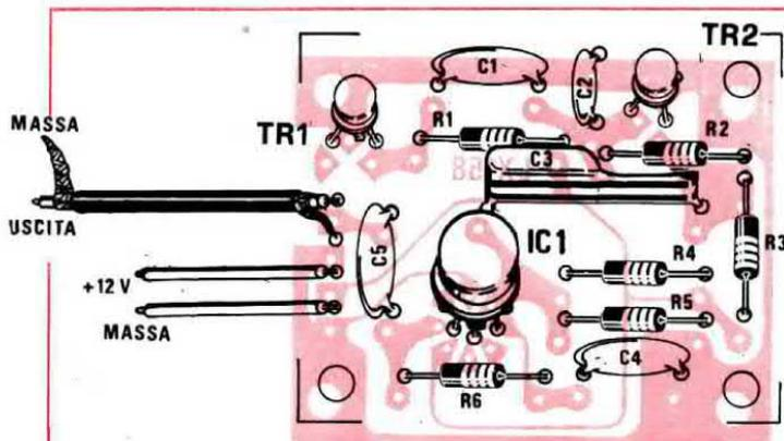
**Fig. 2** Schema pratico di montaggio del generatore di rumore bianco. Inserendo sul circuito l'integrato IC1, porre attenzione a non confondere i terminali.
