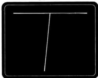
**Fig. 8** Misurando SCR di piccolissima potenza, non rileveremo mai sull'oscilloscopio tante righe orizzontali come indicato in fig. 2, bensì una figura simile a quella indicata in questa foto. Questo perché il gate di tale SCR si eccita sempre con una debolissima corrente.
