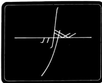
duce sia con la semionda positiva che con quella negativa. Questa caratteristica viene ben evidenziata dal tracciacurve il quale vi permetterà, in possesso di un diodo che non sapete se è un SCR o un TRIAC, di stabilire a quale categoria esso appartenga.
