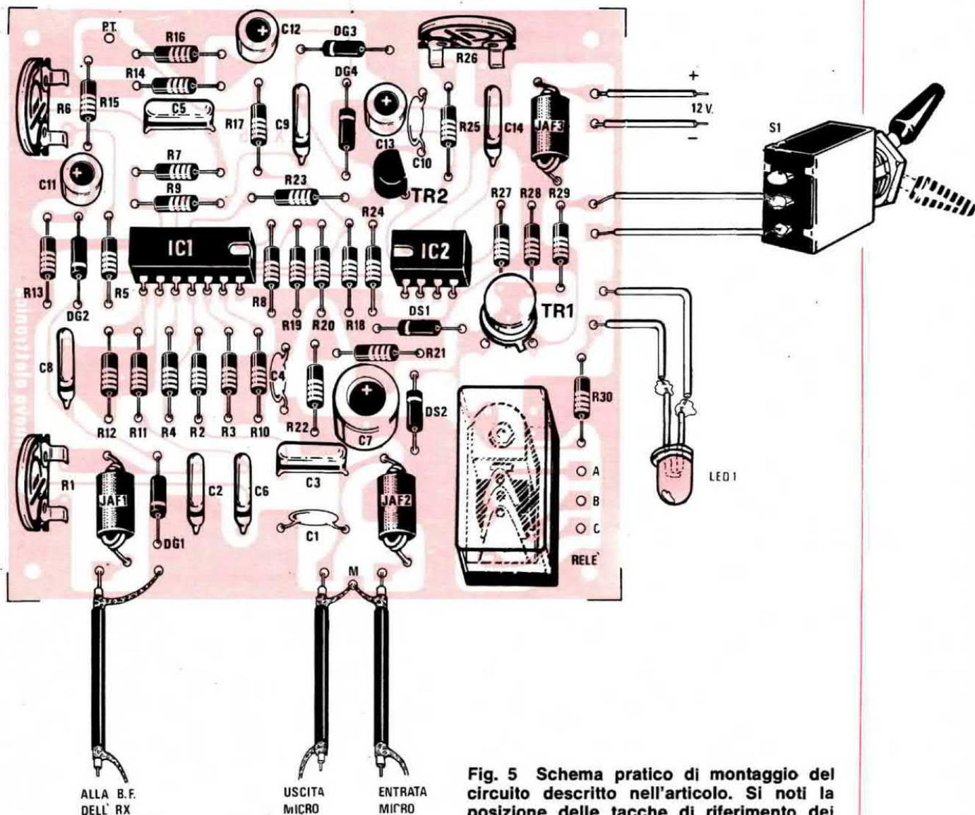
**Fig. 5** Schema pratico di montaggio del circuito descritto nell'articolo. Si noti la posizione delle tacche di riferimento dei due integrati IC1 e IC2 e le connessioni relative al diodo led e all'interruttore S1.
