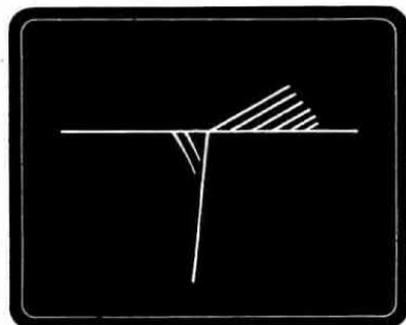
Fig. 13 Invertendo per errore l'Anodo 1 con l'Anodo 2, sullo schermo dell'oscilloscopio otterremo una T, però ben diversa da quella che ci forniva un SCR (vedi foto 7). Il tracciacurve quindi ci permette di individuare pure questi due terminali. In una realizzazione pratica infatti è molto importante non confondere l'A1 con l'A2.
