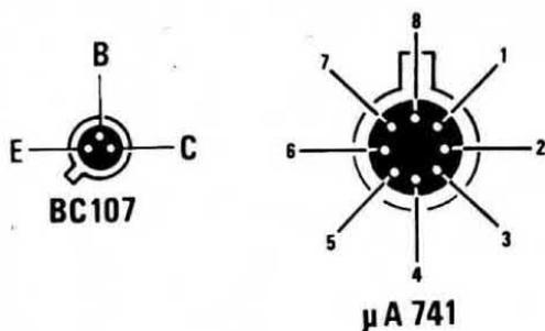
**Fig. 4** In questo disegno sono riportate le connessioni del transistor e dell'integrato impiegato per la realizzazione del progetto. Ricordarsi che i terminali sono visti da sotto, cioè dal lato da cui fuoriescono dal corpo.
