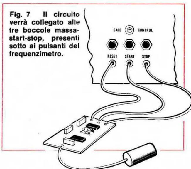
**Fig. 7** Il circuito verrà collegato alle tre bocche massa-start-stop, presenti sotto ai pulsanti del frequenzimetro.
