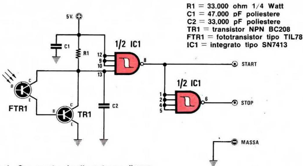
**Fig. 1** Con questo circuito potremo rilevare i tempi che intercorrono tra due stati, cioè tra luce-buio o viceversa.
