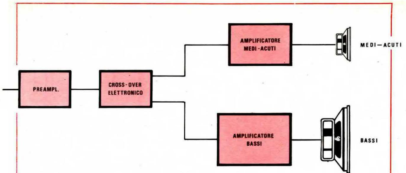
**Fig. 5** Il cross-over elettronico, come vedesi in figura, andrà inserito tra il preamplificatore e i due amplificatori finali di potenza. Come precisato nell'articolo, l'amplificatore dei medi-acuti può risultare pari ad una potenza di circa  $1/3$  rispetto all'amplificatore impiegato per il canale dei « bassi ».
