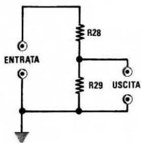
**Fig. 3** Se avessimo la necessità di attenuare il segnale presente all'uscita del decoder, potremo applicare su tale uscita il partitore resistivo visibile in figura. Per i valori vedere la tabella riportata nella pagina successiva.
