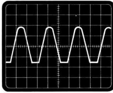
**Fig. 5** Se noterete, come vedesi in figura, che la sinusoide viene tagliata sulla sola parte inferiore, ciò significa che nell'amplificatore il transistor TR6 agisce prima di TR5, quindi occorre aumentare il valore di R13.
