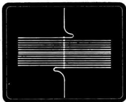
Fig. 11 Anche per i triac, sullo schermo dell'oscilloscopio apparirà a bassa corrente di gate la fascia composta da tante righe orizzontali, come indicato in fig. 2. Aumentando la corrente di gate, quando il triac si ecciterà sullo schermo dell'oscilloscopio apparirà la figura visibile in questa foto; vedremo cioè due righe verticali, una delle quali si ripiega verso l'alto e l'altra verso il basso.
