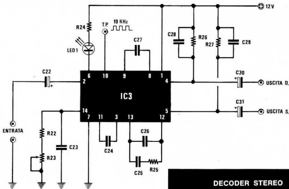
Fig. 2 Schema elettrico del decoder stereo.
