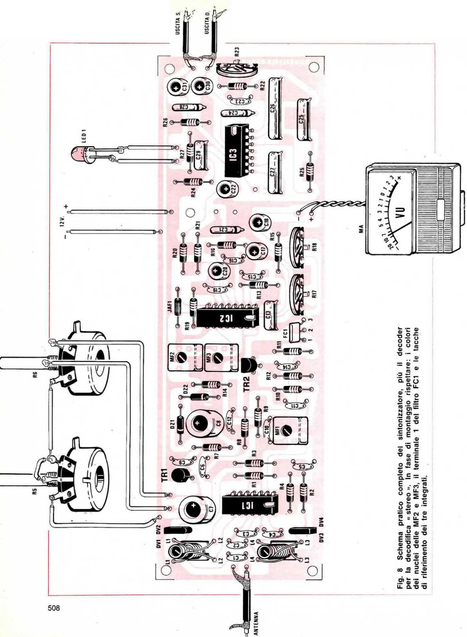
Fig. 8 Schema pratico completo del sintonizzatore, più il decoder per la decodifica « stereo ». In fase di montaggio rispettare: i colori dei nuclei delle MF2 e MF3, il terminale 1 del filtro FC1 e le tacche di riferimento dei tre integrati.
