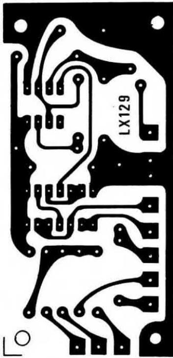
Fig. 3 Circuito stampato a grandezza naturale, necessario per questa realizzazione.
