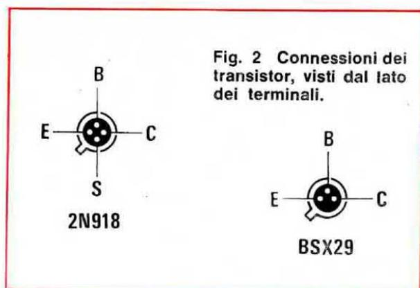
Fig. 2 Connessioni dei transistor, visti dal lato dei terminali.
