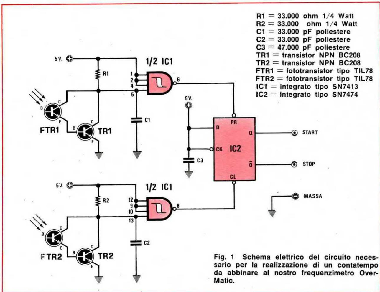
collettore dei due transistor TR1 e TR2, collegati con i fototransistor stessi in configurazione Darlington, avrà un valore che sarà sicuramente al disotto del valore di soglia dei due trigger di Schmitt (i due Nand riportati in figura con il simbolo presente al loro interno stanno appunto ad indicare un trigger di Schmitt) a cui i collettori dei due Darlington sono collegati.
