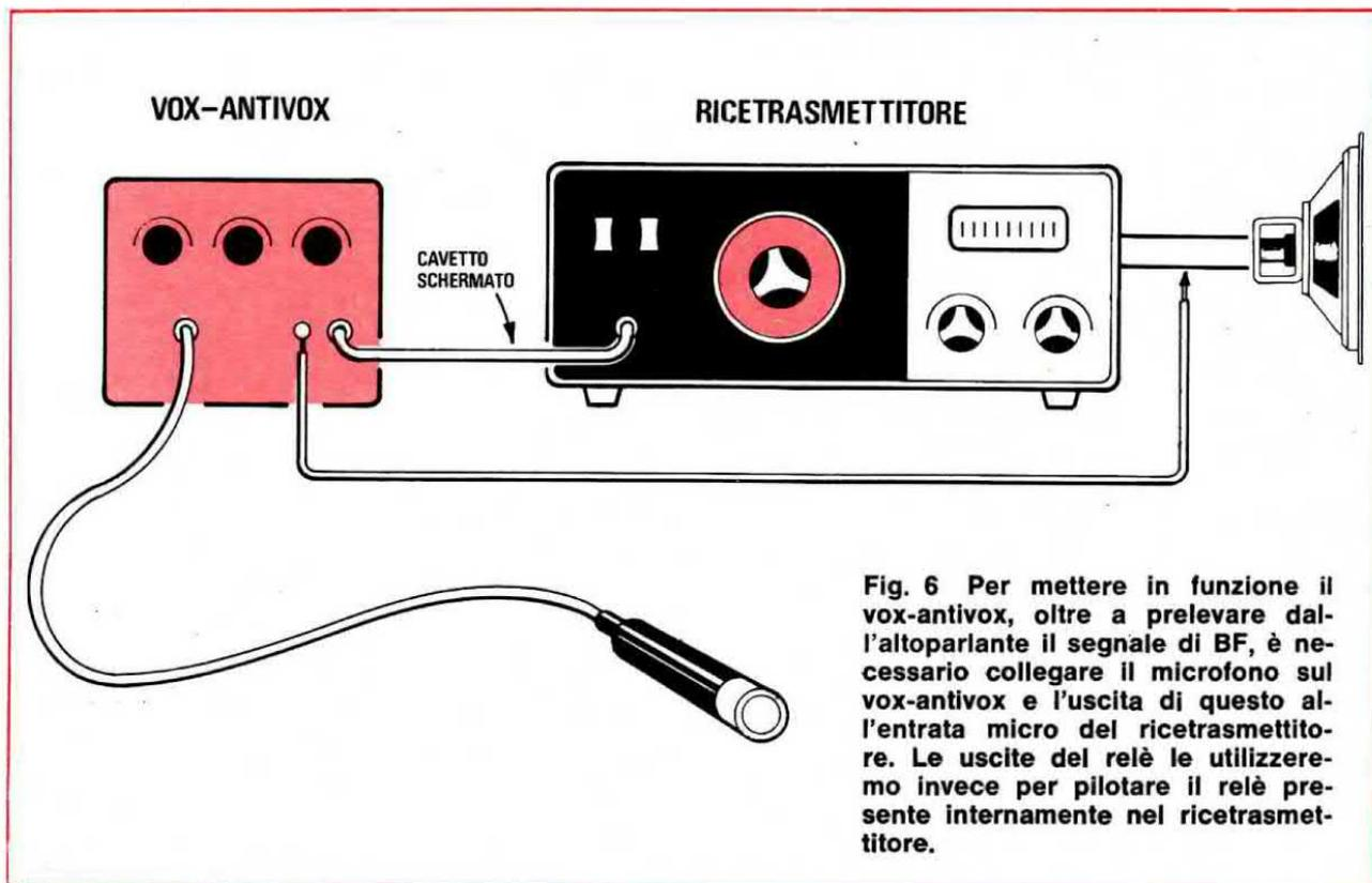
Fig. 6 Per mettere in funzione il vox-antivox, oltre a prelevare dall'altoparlante il segnale di BF, è necessario collegare il microfono sul vox-antivox e l'uscita di questo all'entrata micro del ricetrasmittitore. Le uscite del relé le utilizzeremo invece per pilotare il relé presente internamente nel ricetrasmittitore.
