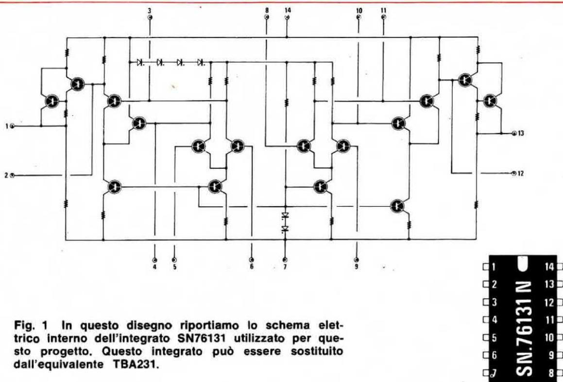
**Fig. 1** In questo disegno riportiamo lo schema elettrico interno dell'integrato SN76131 utilizzato per questo progetto. Questo integrato può essere sostituito dall'equivalente TBA231.
