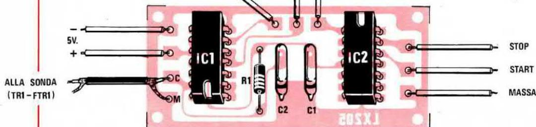
Fig. 3 Schema pratico di montaggio. Tale circuito dovrà risultare collegato alla sonda captatrice tramite un cavetto schermato, per evitare errori di misurazione dovuti ad impulsi spurii.
