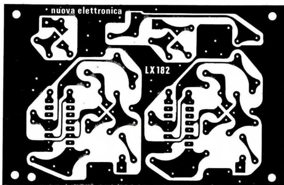
Fig. 3 Disegno del circuito stampato a grandezza naturale. I lettori che volessero usare questo prescaler per collegarlo ad un normale frequenzimetro, dovranno montarne un solo stadio, cioè lo schema completo di fig. 1.
