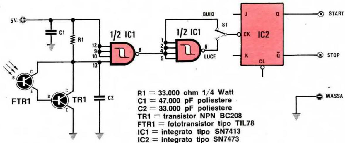
Fig. 1 Schema elettrico del circuito, necessario per il rilevamento di tempi di oggetti in movimento circolare. Di lato la foto del prototipo da noi realizzato collegato al frequenzimetro « OVER-MATIC ».
