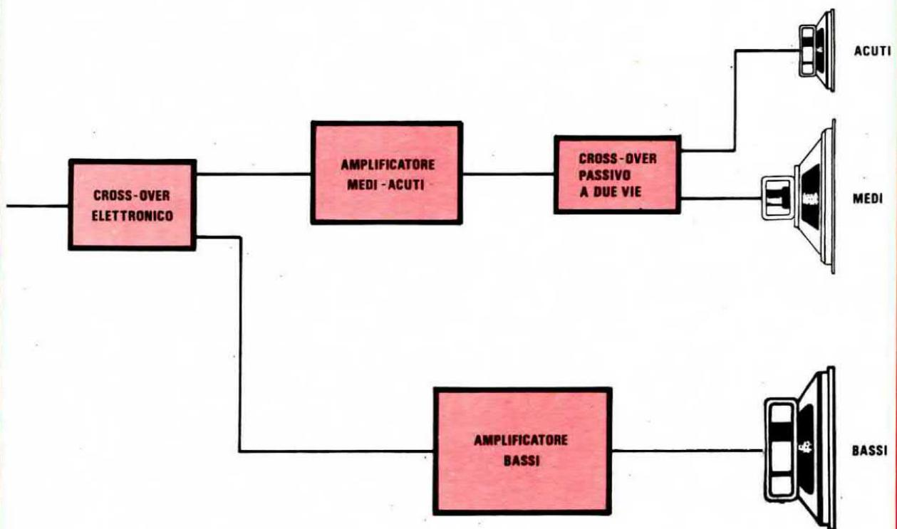
**Fig. 6** Coloro che volessero realizzare un'impianto ancor più perfetto, potranno applicare, sull'uscita dell'amplificatore dei medi-acuti, un filtro cross-over passivo (vedi rivista n. 40-41 a pag. 276) idoneo a separare gli acuti dai medi, come vedesi in figura.
