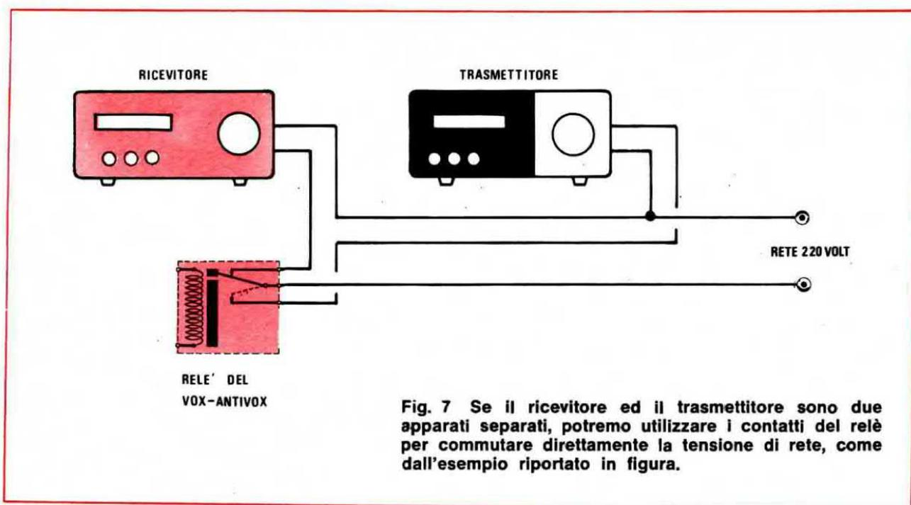
**Fig. 7** Se il ricevitore ed il trasmettitore sono due apparati separati, potremo utilizzare i contatti del relè per commutare direttamente la tensione di rete, come dall'esempio riportato in figura.
