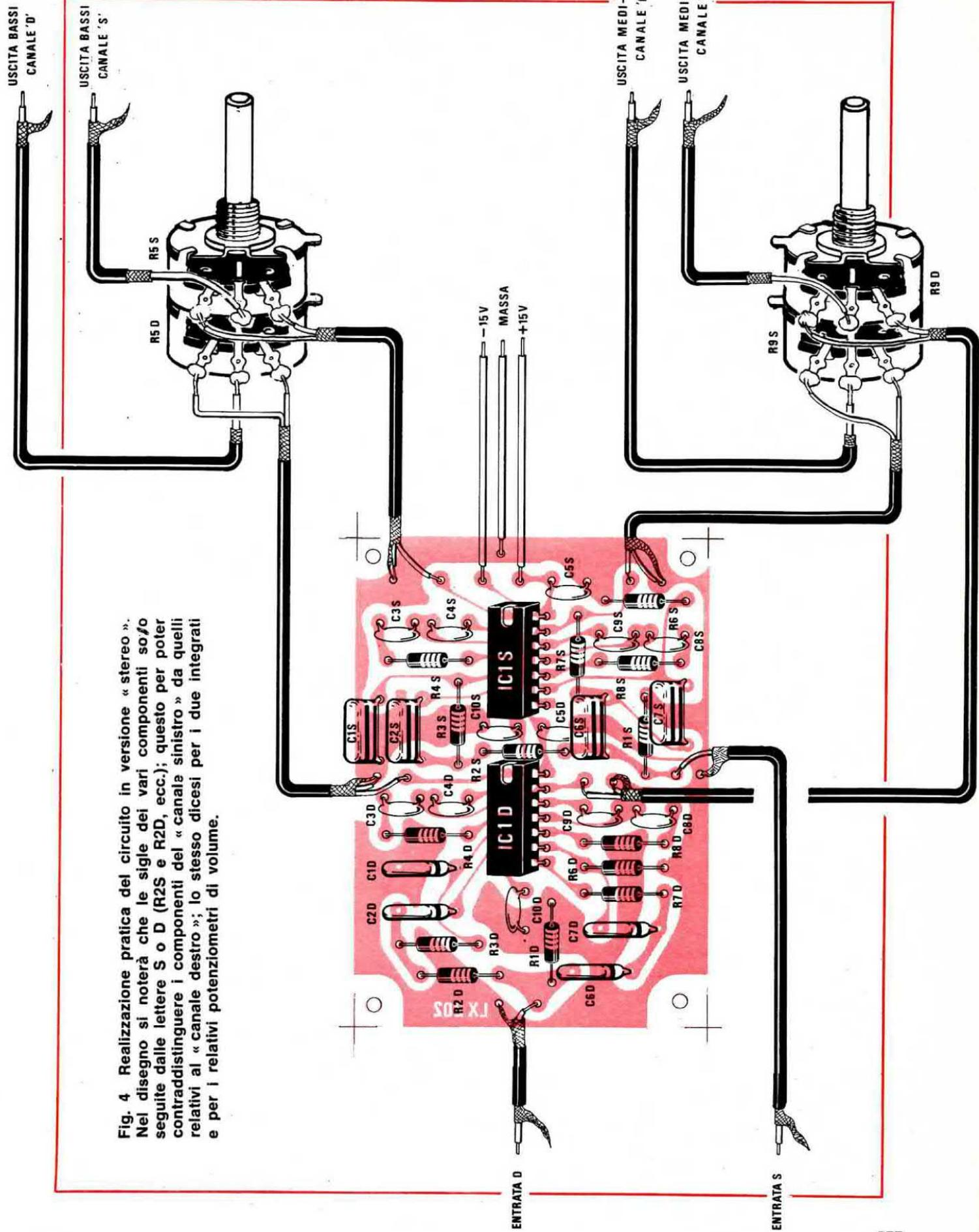
Fig. 4 Realizzazione pratica del circuito in versione « stereo ». Nel disegno si noterà che le sigle dei vari componenti so/fo seguite dalle lettere S o D (R2S e R2D, ecc.); questo per poter contraddistinguere i componenti del « canale sinistro » da quelli relativi al « canale destro »; lo stesso dicasi per i due integrati e per i relativi potenziometri di volume.
