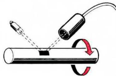
**Fig. 6** Per una precisione assoluta, potremo utilizzare il frequenzimetro in posizione « periodo », fissando sul perno dell'albero in movimento un pezzetto di carta stagnola, in modo che questa rifletta la luce della lampada direttamente sulla sonda captatrice.
