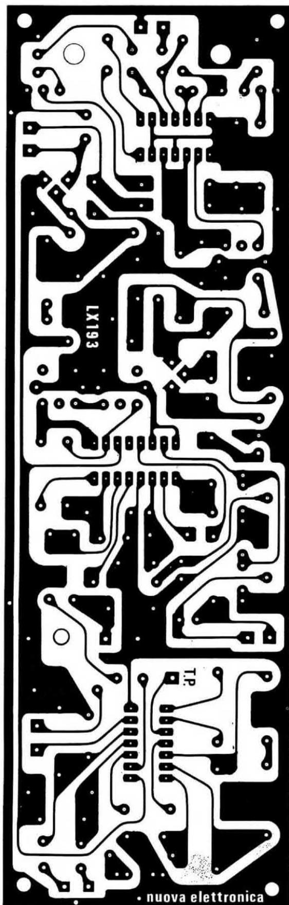
**Fig. 4** Il circuito stampato del sintonizzatore riportato a grandezza naturale.
