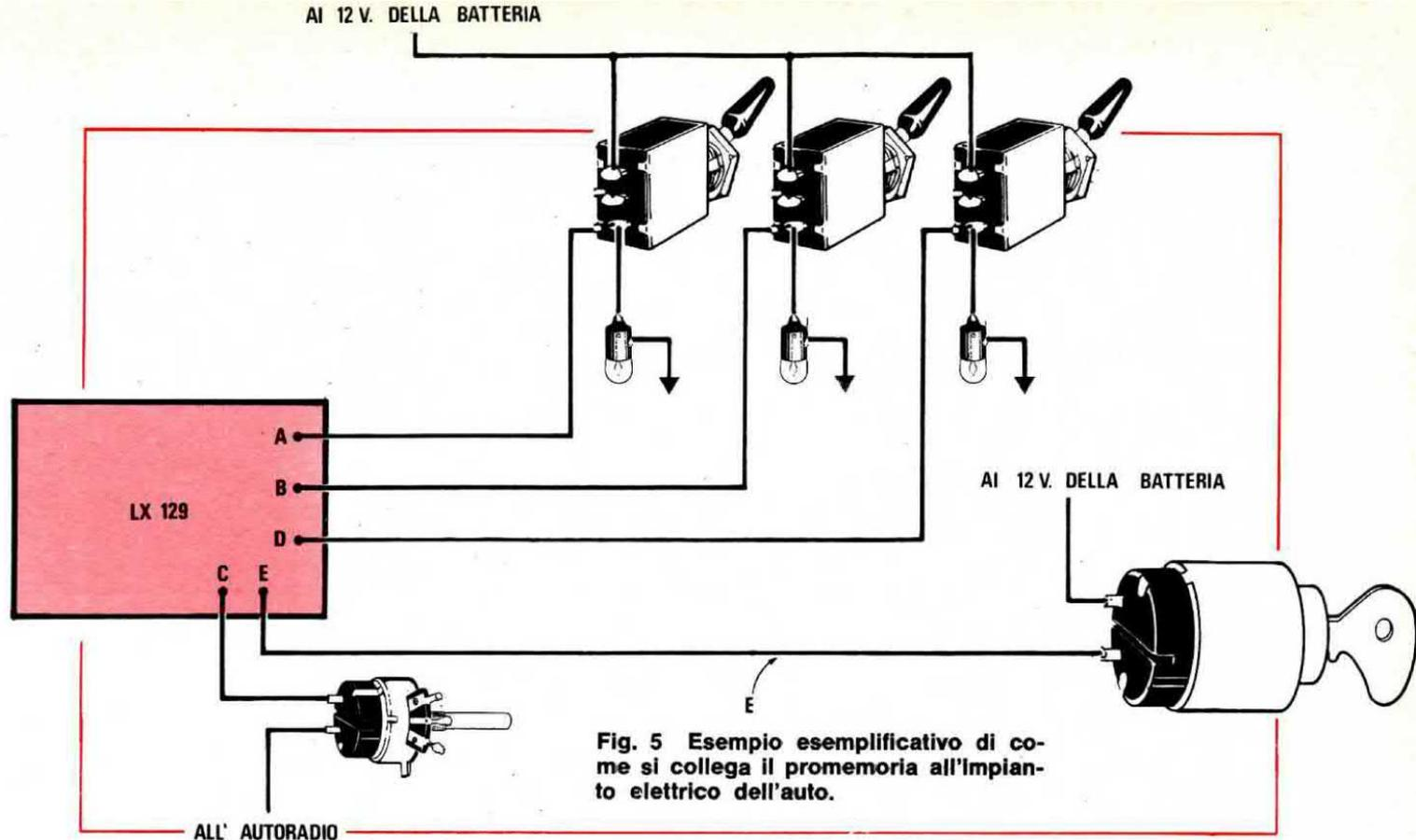
Fig. 5 Esempio esemplificativo di come si collega il promemoria all'impianto elettrico dell'auto.
