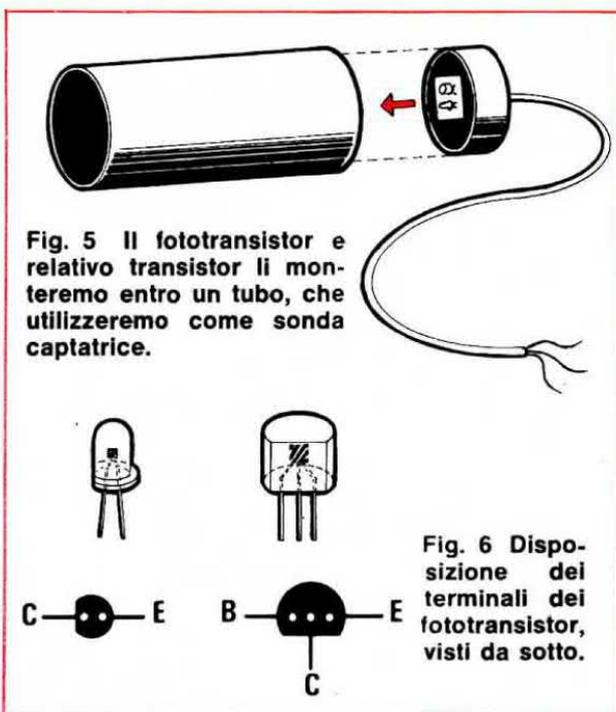
**Fig. 5** Il fototransistor e relativo transistor li monteremo entro un tubo, che utilizzeremo come sonda captatrice.
