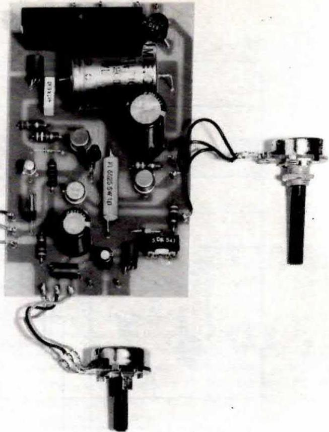
Foto di un prototipo dell'alimentatore. Come descritto nell'articolo, con una semplice modifica è possibile raggiungere senza alcuna difficoltà anche una tensione di 20 volt anziché di 15 come da noi consigliato.
