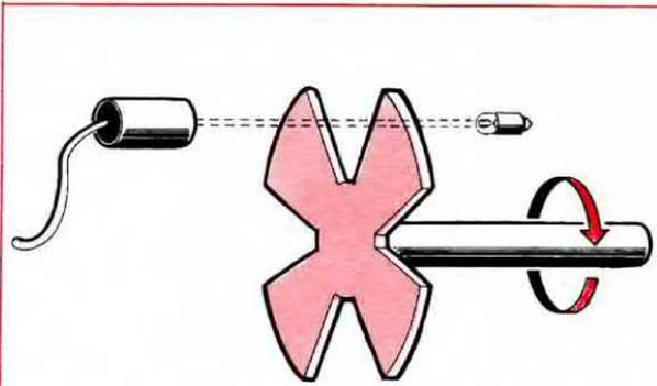
**Fig. 4** Per misurare il numero dei giri al minuto di un albero in movimento, è sufficiente applicare, sul perno, delle pale che interrompano il fascio di luce che colpisce la sonda captatrice. Più elevato risulterà il numero di queste pale, più precisa sarà la misura indicata dal frequenzimetro.
