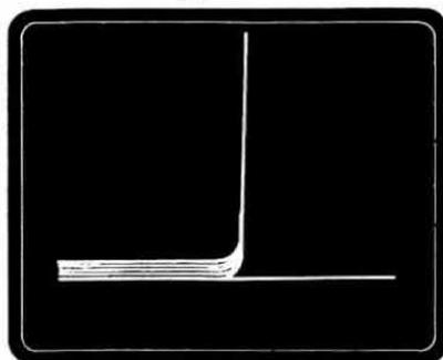
**Fig. 9** Sempre e solo per gli SCR di bassa potenza, se invertiamo il Gate con il Catodo, sullo schermo dell'oscilloscopio appariranno delle curve simili a quelle fornite da un transistor PNP. Una inversione dei terminali Catodo e Anodo ci darà, come per i transistor di potenza, la solita T di fig. 7.
