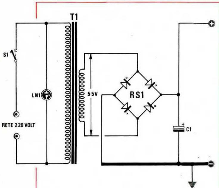
**Fig. 7** Schema elettrico dell'alimentatore
