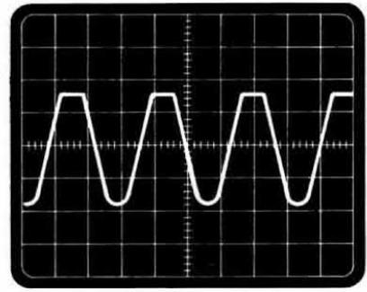
**Fig. 6** Nel caso opposto, cioè se la sinusoide viene tagliata solo sulla parte superiore, è ovvio che sarà il transistor TR5 ad agire prima di TR6, quindi, presentandosi questa condizione, occorrerà aumentare il valore di R12.
