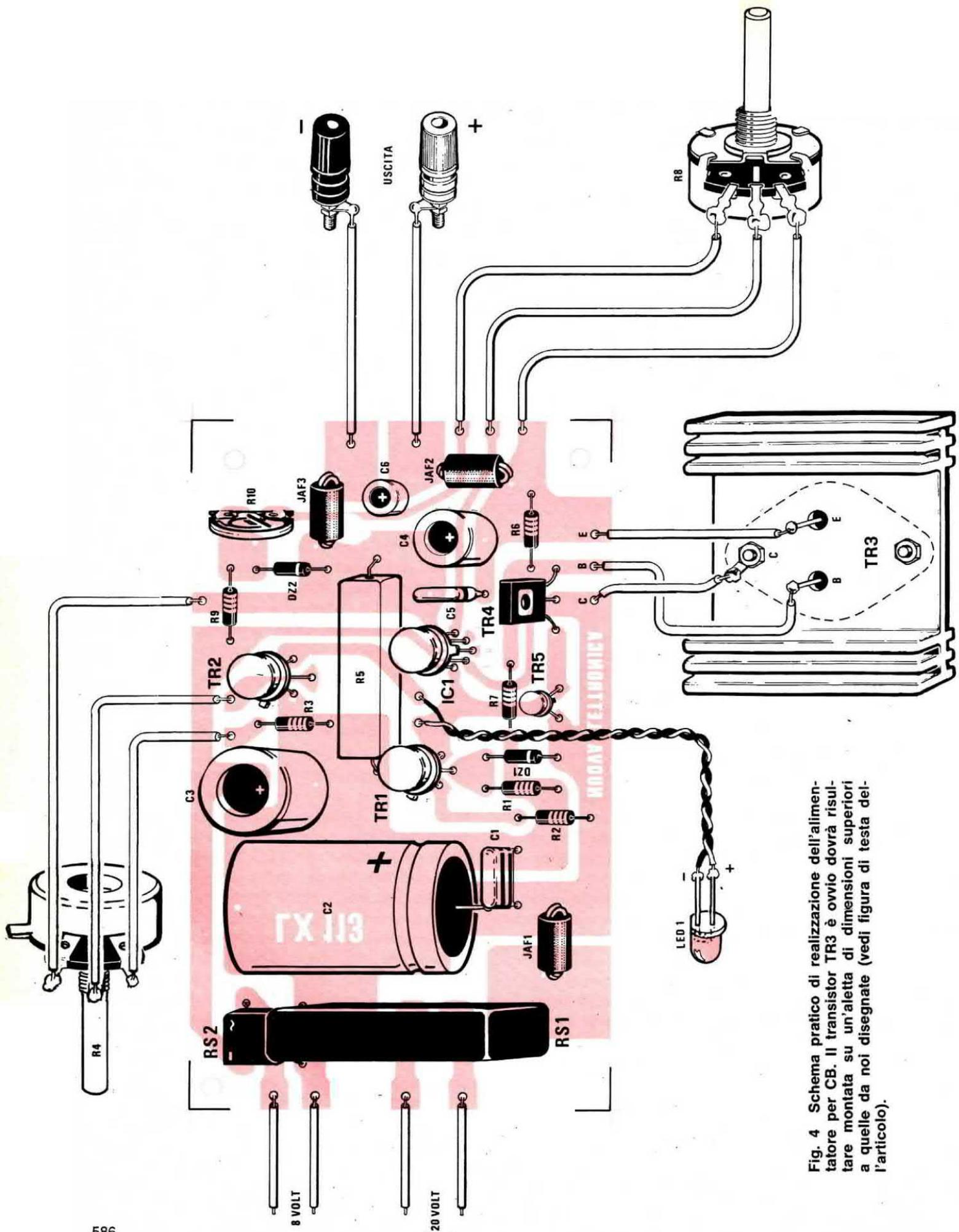
Fig. 4 Schema pratico di realizzazione dell'alimentatore per CB. Il transistor TR3 è ovvio dovrà risultare montata su un'aletta di dimensioni superiori a quelle da noi disegnate (vedi figura di testa dell'articolo).
