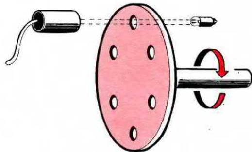
**Fig. 5** Se avremo la possibilità di applicare sull'albero un disco, provvisto di 6 fori come vedesi in figura, otterremo l'innegabile vantaggio di leggere direttamente sul frequenzimetro il numero esatto dei giri al minuto, con la semplice aggiunta di uno 0 rispetto alla cifra indicata.
