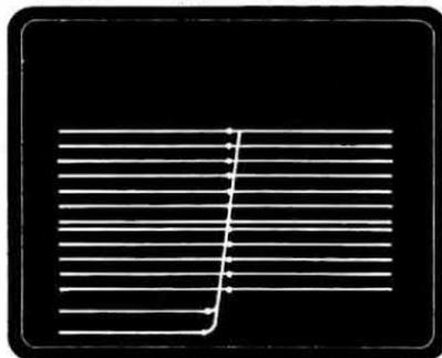
**Fig. 7** Se inavvertitamente confondessimo l'Anodo con il Catodo, il tracciacurve è in grado di indicarci anche questo errore, poiché, anziché apparire sullo schermo la fascia composta da tante righe orizzontali, apparirebbe come in questa foto una semplice T.
