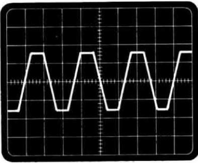
**Fig. 4** Se il circuito di protezione è perfettamente bilanciato, noterete, aumentando notevolmente l'ampiezza del segnale d'ingresso, che in uscita l'onda sinusoidale viene tagliata in modo simmetrico su entrambe le estremità.
