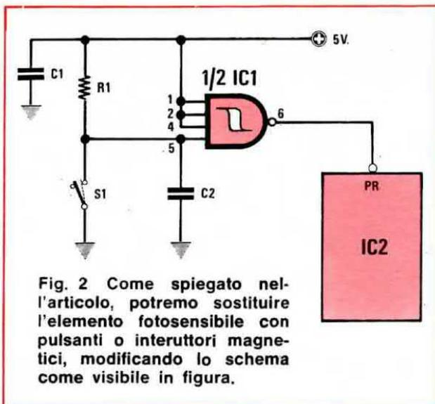
Fig. 2 Come spiegato nell'articolo, potremo sostituire l'elemento fotosensibile con pulsanti o interruttori magnetici, modificando lo schema come visibile in figura.
