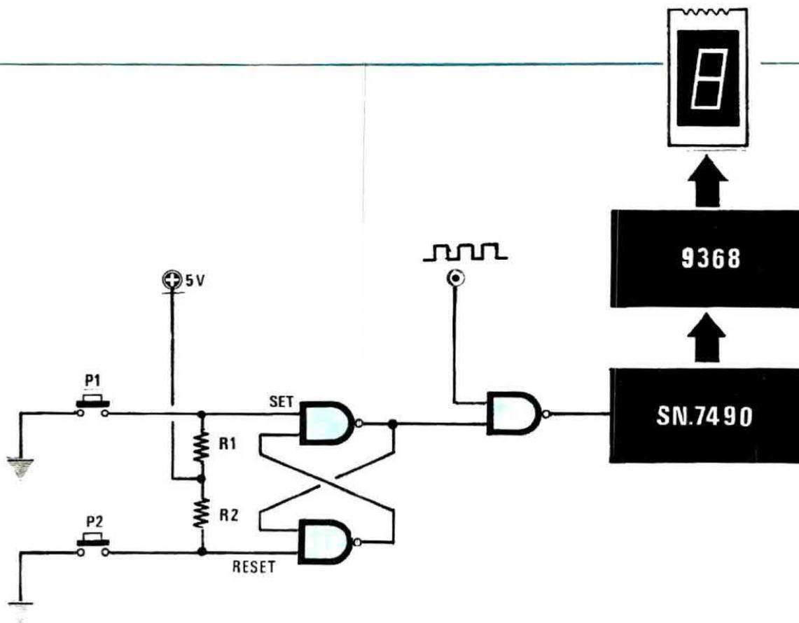
Fig. 12 Schema di principio di come si può sfruttare un flip-flop per realizzare un semplice cronometro digitale. Pigiando il pulsante P1, sull'uscita Q abbiamo una condizione logica 1 e in tal modo la frequenza dei 100 Hz può passare attraverso al terzo nand e raggiungere i contatori SN7490. Pigiando il pulsante P2 invertiremo la condizione logica sull'uscita Q ed il terzo nand funzionerà così da interruttore aperto bloccando il conteggio.
