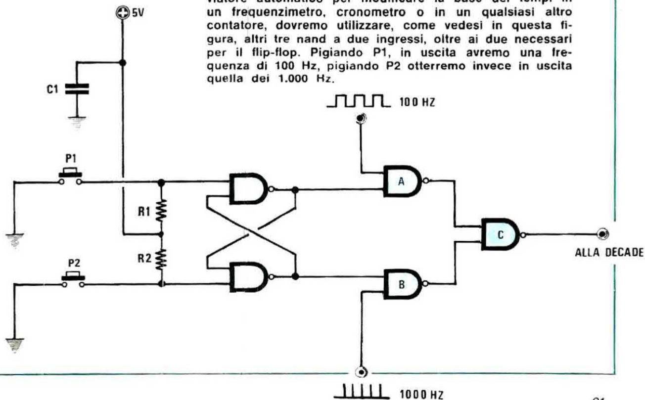
Fig. 13 Se volessimo con un flip-flop realizzare un deviatore automatico per modificare la base dei tempi in un frequenzimetro, cronometro o in un qualsiasi altro contatore, dovremo utilizzare, come vedesi in questa figura, altri tre nand a due ingressi, oltre ai due necessari per il flip-flop. Pigiando P1, in uscita avremo una frequenza di 100 Hz, pigiando P2 otterremo invece in uscita quella dei 1.000 Hz.
