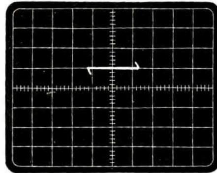
Fig. 15 Un diodo DIAC, a differenza di qualsiasi altro diodo, ci presenta sull'oscilloscopio una linea orizzontale, alle cui estremità sono presenti due cortissime linee oblique, come vedesi nella foto.
