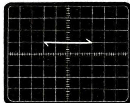
Fig. 17 Spostando il deviatore da « 20 volt X divis » su quello « 5 volt X divis » qualsiasi traccia orizzontale verrà ampliata di ben 4 volte, questo perché nel primo caso ogni quadretto orizzontale corrisponde ad una tensione di 20 volt, nel secondo caso a soli 5 volt.
