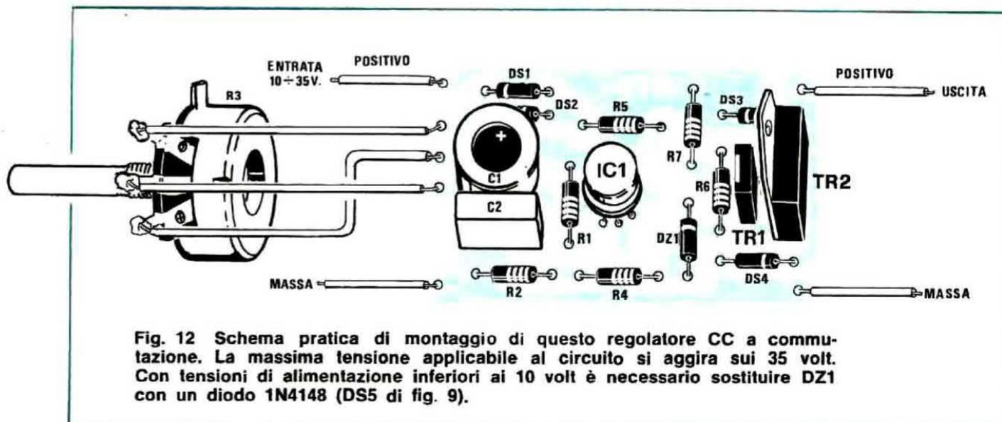
Fig. 12 Schema pratica di montaggio di questo regolatore CC a commutazione. La massima tensione applicabile al circuito si aggira sui 35 volt. Con tensioni di alimentazione inferiori ai 10 volt è necessario sostituire DZ1 con un diodo 1N4148 (DS5 di fig. 9).
