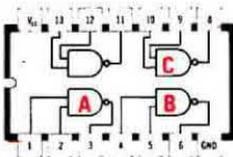
**Fig. 19** Disposizione dei vari nand e inverter nell'interno degli integrati.
