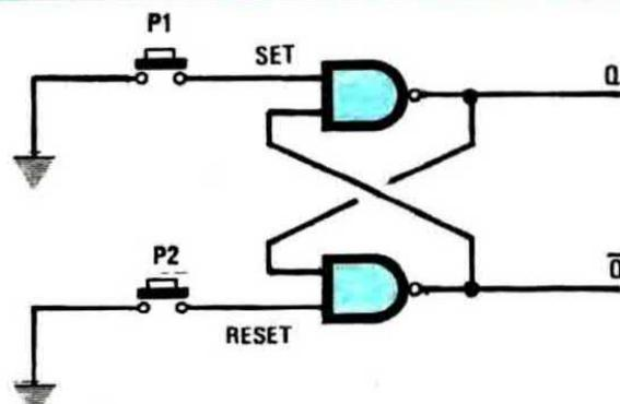
Fig. 5 Collegando i terminali di due nand a due ingressi, come vedesi in questo disegno, avremo già realizzato un flip-flop tipo SR. Per eccitare questo flip-flop è necessario porre a massa (condizione logica 0) l'uno o l'altro dei due terminali
