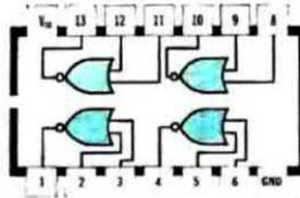
Fig. 3 Poiché nelle nostre esperienze abbiamo presentato dei circuiti che impiegano dei nor, anziché dei nand, vi diremo che nell'interno dell'integrato SN7402 sono presenti quattro nor a due ingressi.
