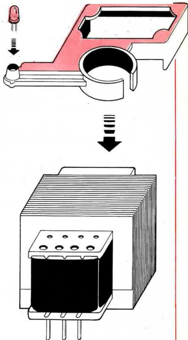
Fig. 6 Nel kit troverete un supporto in plastica simile a quello disegnato in alto, che infilato sul trasformatore T1, servirà da sostegno per il diodo led e per l'altoparlante, il cui magnete si innesterà nel vano circolare. Nell'inserire il trasformatore sul circuito stampato non potrete incorrere in nessun errore, in quanto il lato provvisto di tre terminali è, come intuibile, il secondario a bassa tensione.
