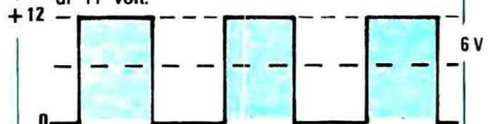
Fig. 7 Se la durata della pausa eguaglia la durata della erogazione, la luminosità della lampadina o la velocità del motore collegato in uscita si ridurrà alla metà, proprio come se li alimentassimo con soli 6 volt.
