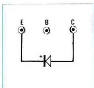
Fig. 1 Per controllare un diodo con il tracciacurve dovremo sfruttare le due sole bocchie E-C, come del resto risulta anche disegnato sul pannello dello strumento.
