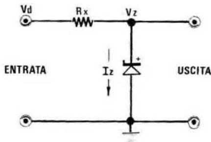
Fig. 13 Calcolare il valore della resistenza RX da porre in serie il diodo zener senza tener conto della corrente assorbita dal « carico » porterà sempre ad un errore, in quanto collegando il carico, la corrente che attraversa lo zener automaticamente si riduce.
