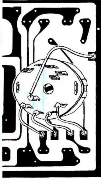
Fig. 7 I terminali del commutatore S2 andranno collegati con dei corti spezzi di filo sulle piste del circuito stampato come appare chiaramente visibile in questo disegno.
