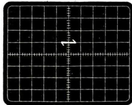
Fig. 16 Se il diodo diac sotto controllo ci fa apparire sullo schermo dell'oscilloscopio una linea orizzontale non più lunga di un centimetro, noi potremo come indicato qui sotto ampliarla di circa 4 volte.
