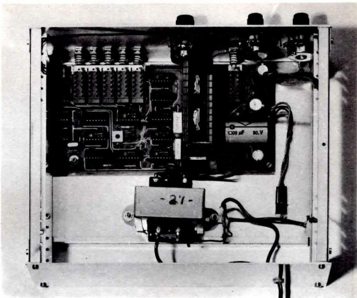
**Fig. 21** Come verrà montato nell'interno del mobile, il circuito stampato del generatore di barre. Si noti la posizione del trasformatore di alimentazione e l'integrato uA. 7805 (a destra) fissato sul pannello di sostegno orizzontale.
