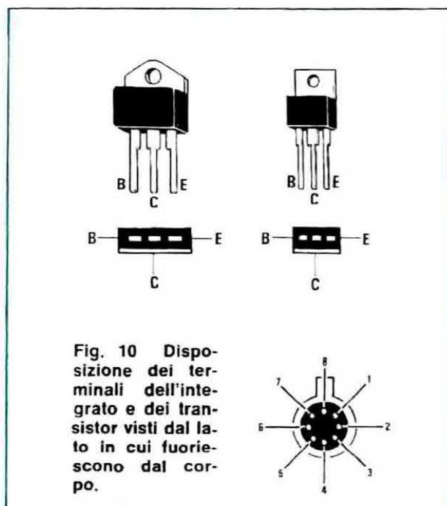
Fig. 10 Disposizione dei terminali dell'integrato e dei transistor visti dal lato in cui fuoriescono dal corpo.
