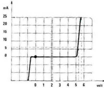
Fig. 12 Questo diodo avendo la linea verticale molto più ripida del precedente (fig. 11) ci conferma che facendo scorrere attraverso ad esso 5 mA, stabilizza la tensione a 5,1 volt ma anche se aumentassimo la corrente a circa 25 mA, le variazioni massime risulterebbero di soli 0,2 volt (c'è 5,4 volt).
