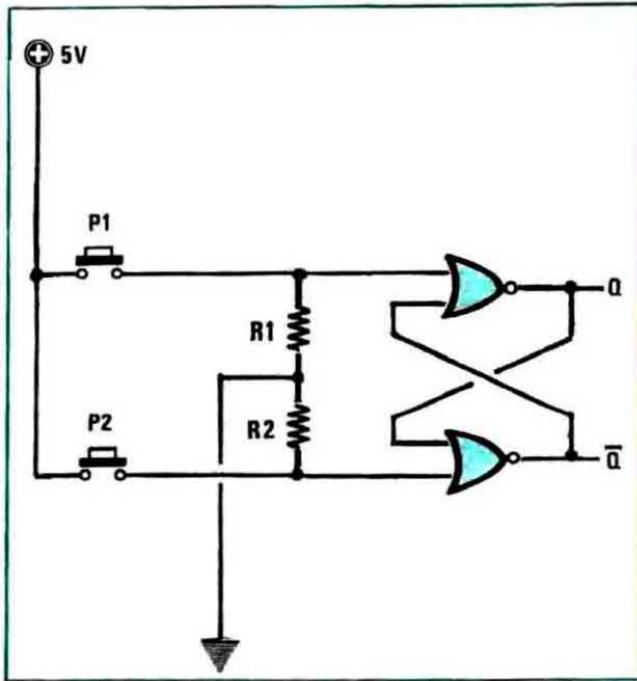
**Fig. 9** Se volessimo realizzare del flip-flop utilizzando dei NOR anziché dei Nand dovremo necessariamente collegare le due resistenze R1-R2 sui terminali d'entrata per mantenerli in condizione 0 e fornire tramite i due pulsanti la condizione logica 1.
