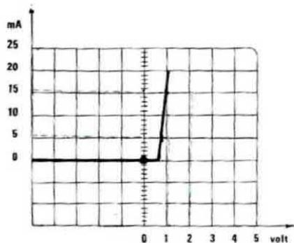
**Fig. 6** Poiché ogni quadretto verticale corrisponde a 5 milliamper, se nel diodo al silicio scorrono correnti comprese tra 0 e 5 mA, si ha una caduta di tensione di circa 0,7 volt; con 15 mA si ha invece una caduta di circa 1 volt.
