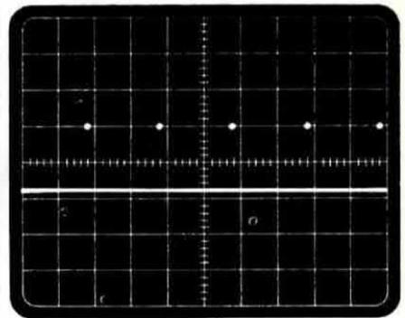
Fig. 4 Forma del sincronismo verticale che rileverete sul piedino 8 dell'integrato IC11 cioè l'SN7492.
