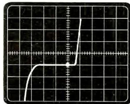
Fig. 9 I diodi zener, a differenza dei diodi al germanio ed al silicio, ci faranno apparire sullo schermo dell'oscilloscopio una figura con due tratti verticali agli estremi.
