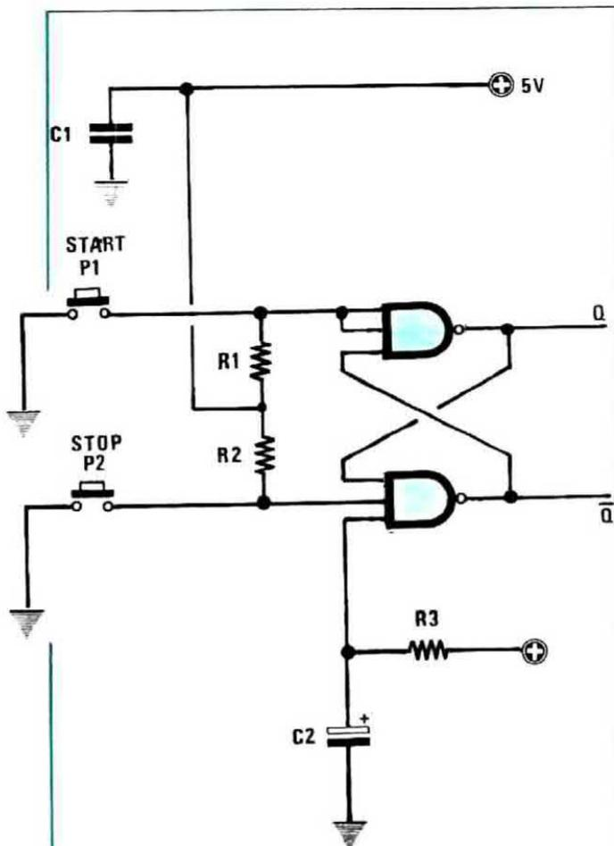
**Fig. 8** Se alimentiamo un flip-flop realizzato con nand a due ingressi, sulle uscite Q e -Q potremo trovare una condizione logica iniziale del tutto casuale, cioè un 1 o uno 0 indifferentemente. Se ci necessita eliminare questo inconveniente dovremo utilizzare dei nand a tre ingressi collegandoli come indicato in disegno (la resistenza R3 va collegata ai 5 volt positivi).
