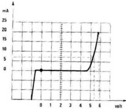
Fig. 11 Meno risulta ripido il tratto di linea verticale a destra del « punto zero », meno stabile risulta la tensione di zener. In questo esempio si può notare che facendo scorrere nel diodo 5 mA si ha una stabilizzazione a 5,1 volt, ma questa raggiungerebbe i 6 volt se la corrente aumentasse a circa 20 mA.
