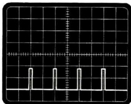
Fig. 4 Aumentando il numero di giri del motore a circa 1.000 giri sullo schermo dell'oscilloscopio appariranno ben 4 impulsi. Si noti come la distanza fra i vari impulsi risulti costante, così come risulta costante la loro ampiezza.
