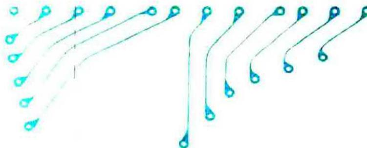
**Fig. 6** Disegno del circuito stampato riportato a grandezza naturale. Tale circuito è a doppia faccia e, come sempre, su di esso risulta riportata la serigrafia dei componenti per facilitarne il montaggio.
