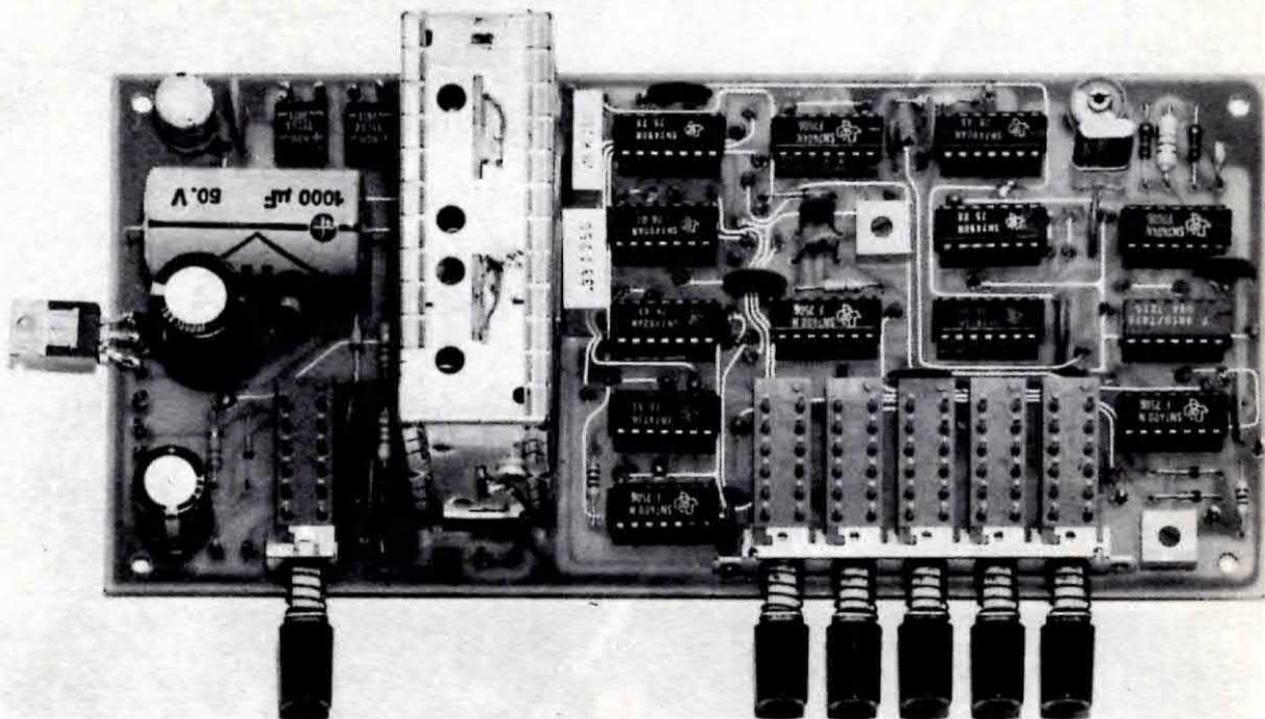
**Fig. 18** Come si presenta a costruzione ultimata il nostro generatore di barre. Si noti a sinistra l'integrato stabilizzatore IC14 (uA.7805) che dovremo poi fissare sul piano orizzontale di alluminio del contenitore, in modo che quest'ultimo espliciti la funzione di aletta di raffreddamento.
