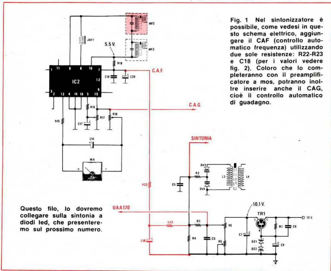
Fig. 1 Nel sintonizzatore è possibile, come vedesi in questo schema elettrico, aggiungere il CAF (controllo automatico frequenza) utilizzando due sole resistenze: R22-R23 e C18 (per i valori vedere fig. 2). Coloro che lo completeranno con il preamplificatore a mos, potranno inoltre inserire anche il CAG, cioè il controllo automatico di guadagno.
