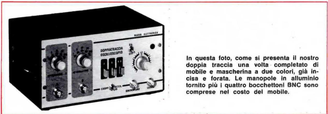
In questa foto, come si presenta il nostro doppia traccia una volta completato di mobile e mascherina a due colori, già incisa e forata. Le manopole in alluminio tornito più i quattro bocchettoni BNC sono comprese nel costo del mobile.
