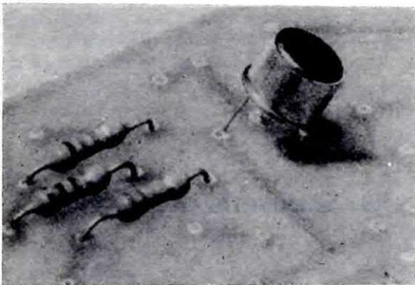
Fig. 22 Quando inserite su un circuito stampato un transistor, imparate a metterlo ben verticale, in special modo se su questo transistor dovete poi applicare un'aletta di raffreddamento.
