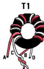
**Fig. 15** Come spiegato nell'articolo, il trasformatore T1 va avvolto utilizzando due fili appaiati e collegando poi l'inizio del primo con la fine del secondo avvolgimento (vedi lettere A-B e C-D fig. 14). È importante che i due fili BC risultino collegati al gate. Per questo trasformatore dovremo scegliere un nucleo toroidale idoneo alla gamma di frequenza in cui desideriamo far lavorare il preamplificatore.
