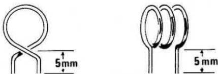
**Fig. 23** Quando avvolgete le bobine sul diametro indicato, cercate possibilmente di farlo a regola d'arte, lasciando come vedesi in disegno circa 5 mm di filo per non tenere né troppo alta né troppo bassa la bobina dal circuito stampato.
