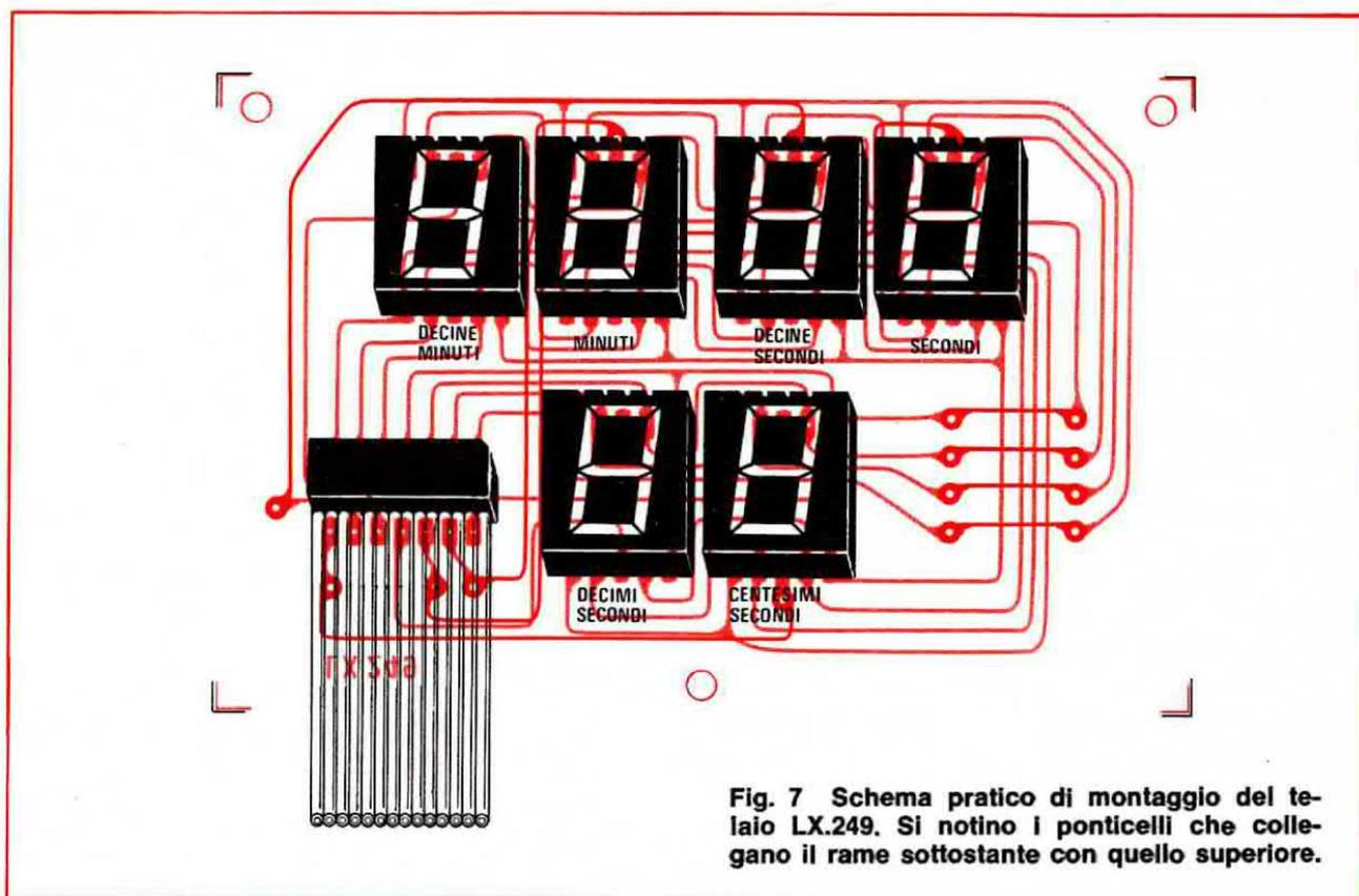
**Fig. 7** Schema pratico di montaggio del telaio LX.249. Si notino i ponticelli che collegano il rame sottostante con quello superiore.
