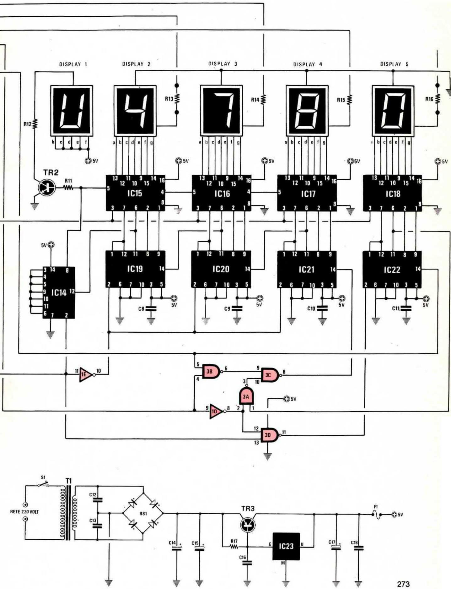
Supponendo ad esempio di avere utilizzato una resistenza R da 10.000 ohm e di applicare fra i piedini 10 e 11 un condensatore da 47.000 pF (cioè da 0,047 mF), noi potremo ottenere in uscita dal monostabile degli impulsi aventi una durata di  $10.000 \times 0,047 \times 0,7 : 1.000.000 = 0,000329$  secondi pari a **329 microsecondi**.
