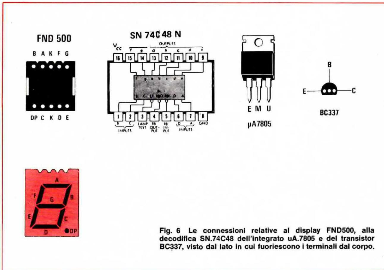
Fig. 6 Le connessioni relative al display FND500, alla decodifica SN.74C48 dell'integrato uA.7805 e del transistor BC337, visto dal lato in cui fuoriescono i terminali dal corpo.
