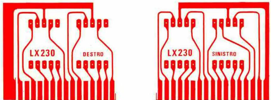
**Fig. 4** I due circuiti stampati necessari per ricevere i quattro display del contagiri.
