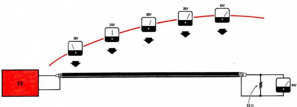
Fig. 4 Se una delle tre impedenze non collima, il cavo entra in risonanza, cioè si comporta come un'antenna (vedi fig. 2) e come tale la tensione varia da un minimo ad un massimo pur rimanendo costante la potenza (varia la corrente). Poiché un wattmetro AF misura la sola tensione, si ottengono in questi casi indicazioni errate.
