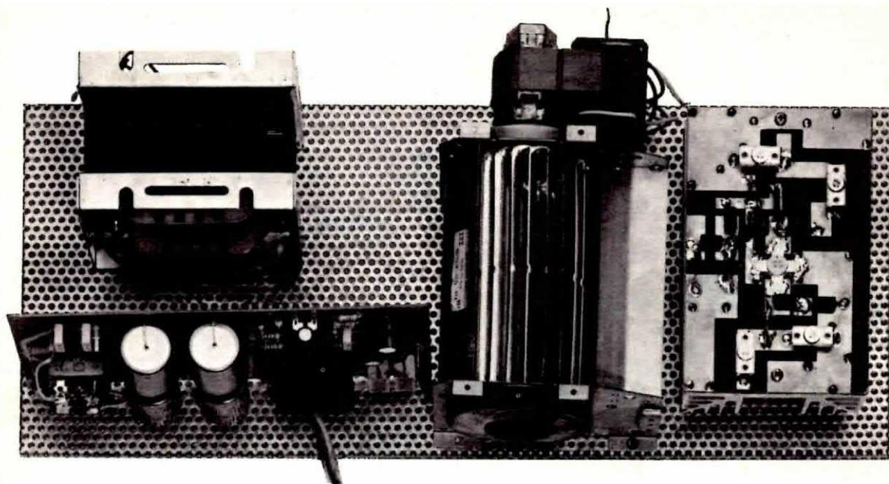
Nell'interno del mobile metallico da noi fornito troverà posto il lineare, la ventola di raffreddamento forzato e il relativo alimentatore di potenza. Il circuito stampato dell'alimentatore è posto in posizione verticale.
