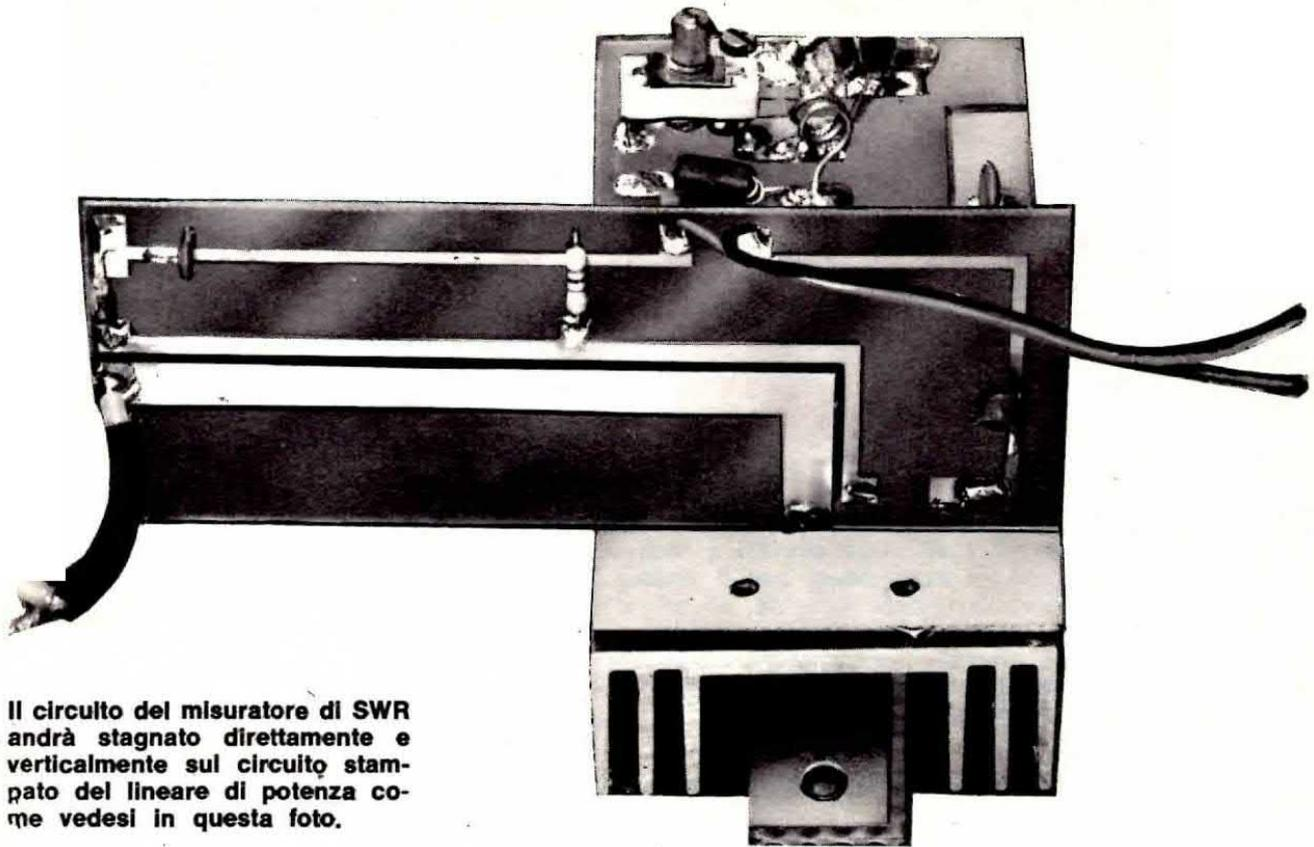
**Il circuito del misuratore di SWR andrà stagnato direttamente e verticalmente sul circuito stampato del lineare di potenza come vedesi in questa foto.**
