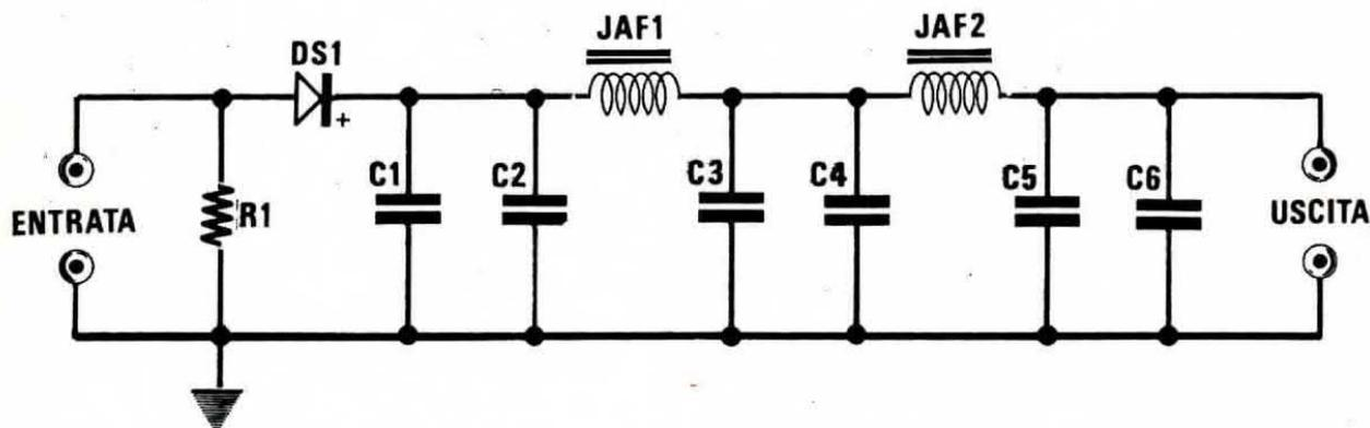
Fig. 11 Schema elettrico della sonda di potenza.
