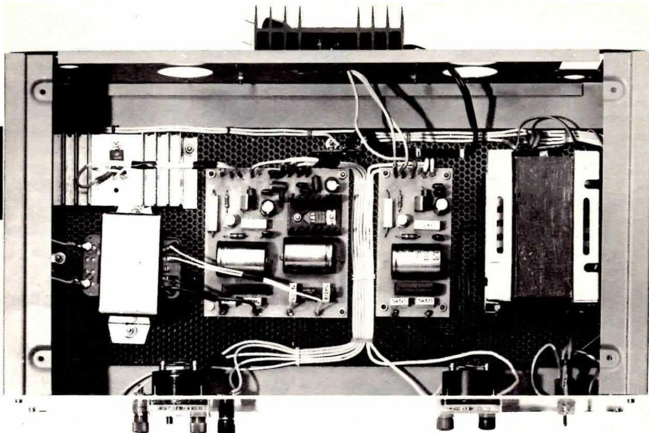
**Nella foto si può vedere come noi abbiamo disposto dentro al mobile i due alimentatori necessari per alimentare il nostro trasmettitore in FM per radio private. Si noti l'aletta di raffreddamento per il darlington MJ 2501 posta sul retro del mobile.**
