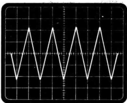
**Fig. 5** Se ruotate oltre al necessario il trimmer R23, constaterete che l'onda da quasi sinusoidale si trasformerà in una perfetta onda triangolare, contemporaneamente da 5 quadretti si abbasserà a 4,5 quadretti come vedesi in figura.
