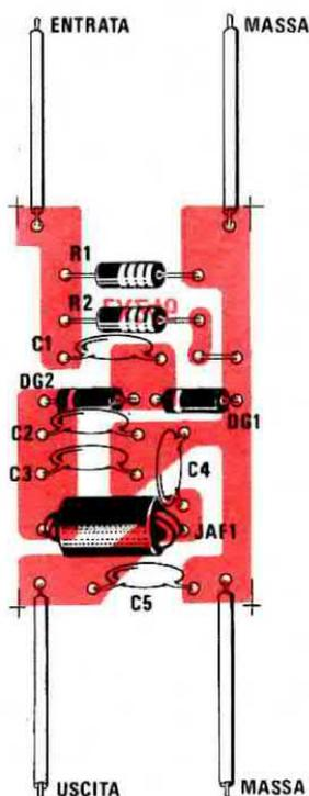
Fig. 7 a destra. Schema pratico di montaggio della sonda.
