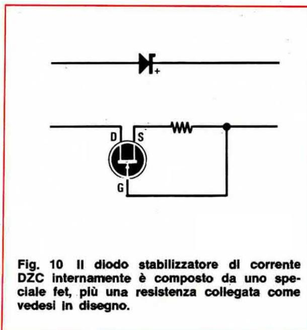
Fig. 10 Il diodo stabilizzatore di corrente DZC internamente è composto da uno speciale fet, più una resistenza collegata come vedesi in disegno.
