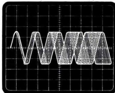
**Fig. 8** Applicando in ingresso al compressore un segnale di BF da 100 millivolt, vedrete le cinque sinusoidi espandersi. Quando la 5ª sinusoide toccherà la 4ª voi modulerete in FM con una deviazione di circa 75 KHz.
