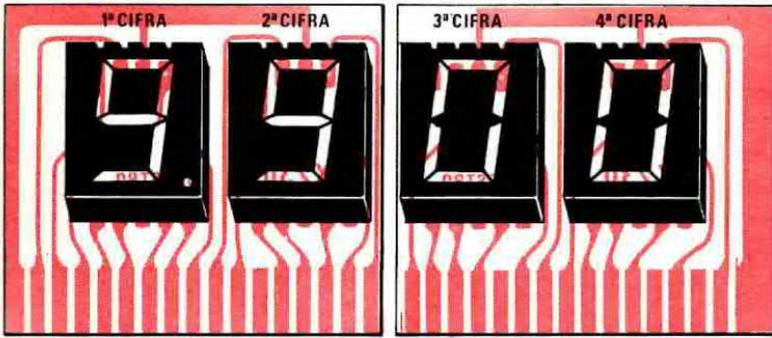
Fig. 5 Sui due circuiti LX230 monteremo i quattro display tenendo la parte zigrinata rivolta verso l'alto.
