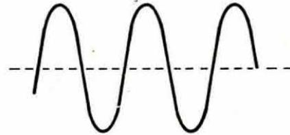
**Fig. 4** In classe A, amplificando lo stesso transistor sia la semionda negativa che quella positiva, non si verifica mai l'inconveniente che può presentarsi in classe B, quindi l'onda amplificata risulta perfetta.
