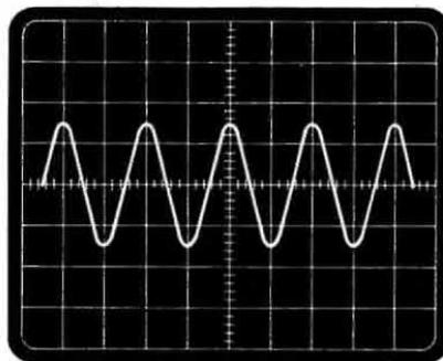
**Fig. 7** Sempre sul punto TP.B in assenza di segnale vedrete apparire sull'oscilloscopio 5 sinusoidi alte 3,3 quadretti.
