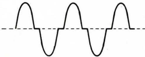
**Fig. 3** In classe B, quando si passa dalla semionda negativa a quella positiva o viceversa può esserci un brevissimo intervallo di tempo in cui nessuno dei due transistor conduce, cioè si può avere una distorsione di cross-over, come vedesi in disegno.
