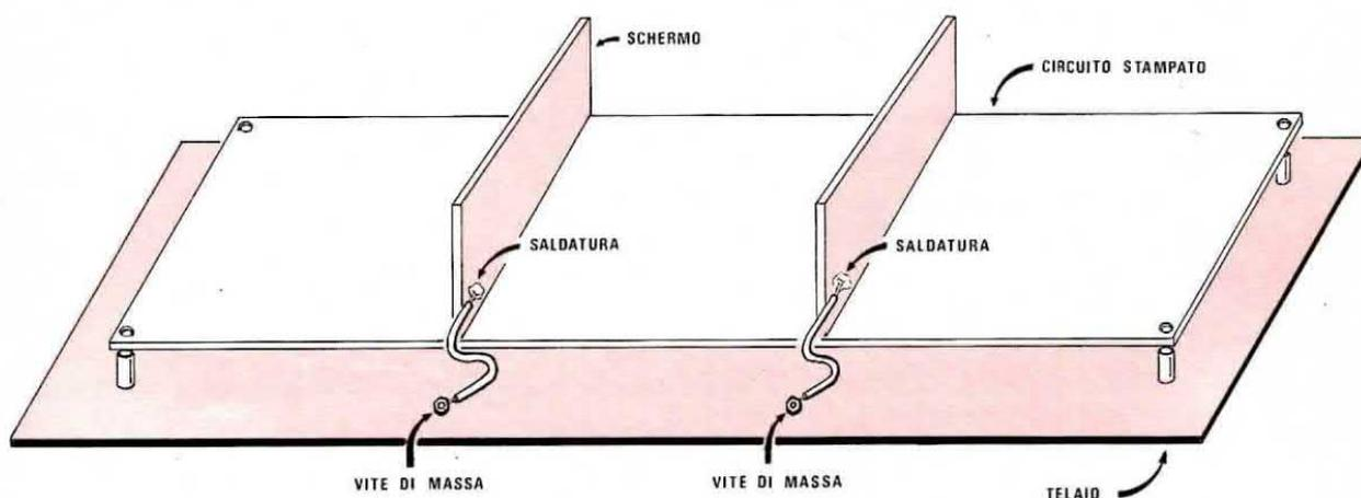
**Fig. 16** Per prevenire autooscillazioni consigliamo, come vedesi in questo disegno, di collegare alla massa del telaio di supporto (piastra forata) tutti gli schermi verticali posti sugli stampati LX239 e LX240. Il collegamento andrà effettuato da un solo lato.
