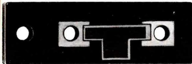
**Fig. 14** Lo strato di carbone può assumere forme e disegni diversi, anche perché la fresatura necessaria per portare l'esatto valore a 52 ohm, può essere effettuata ai margini, o al centro.
