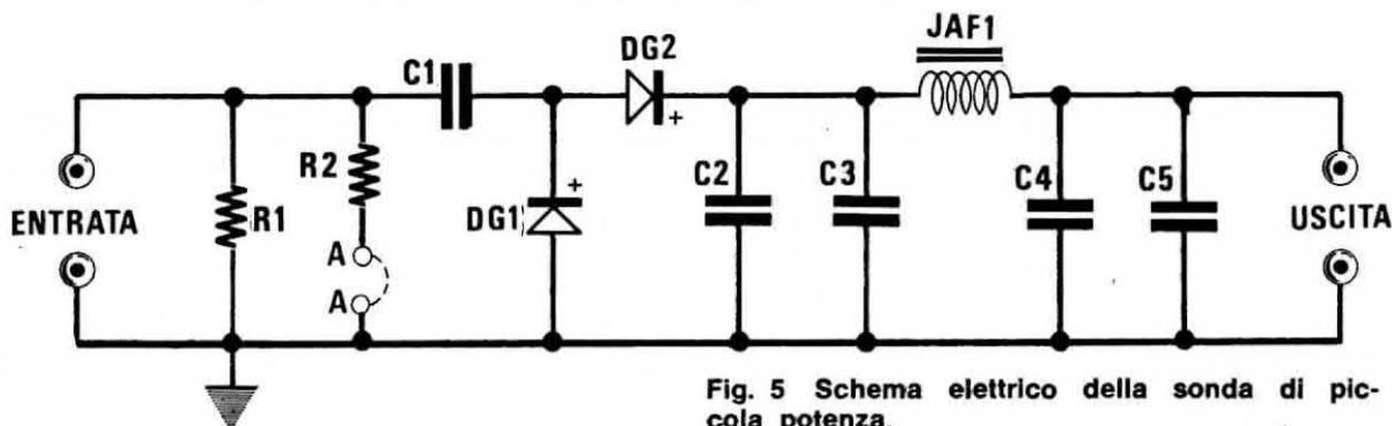
Fig. 5 Schema elettrico della sonda di piccola potenza.
