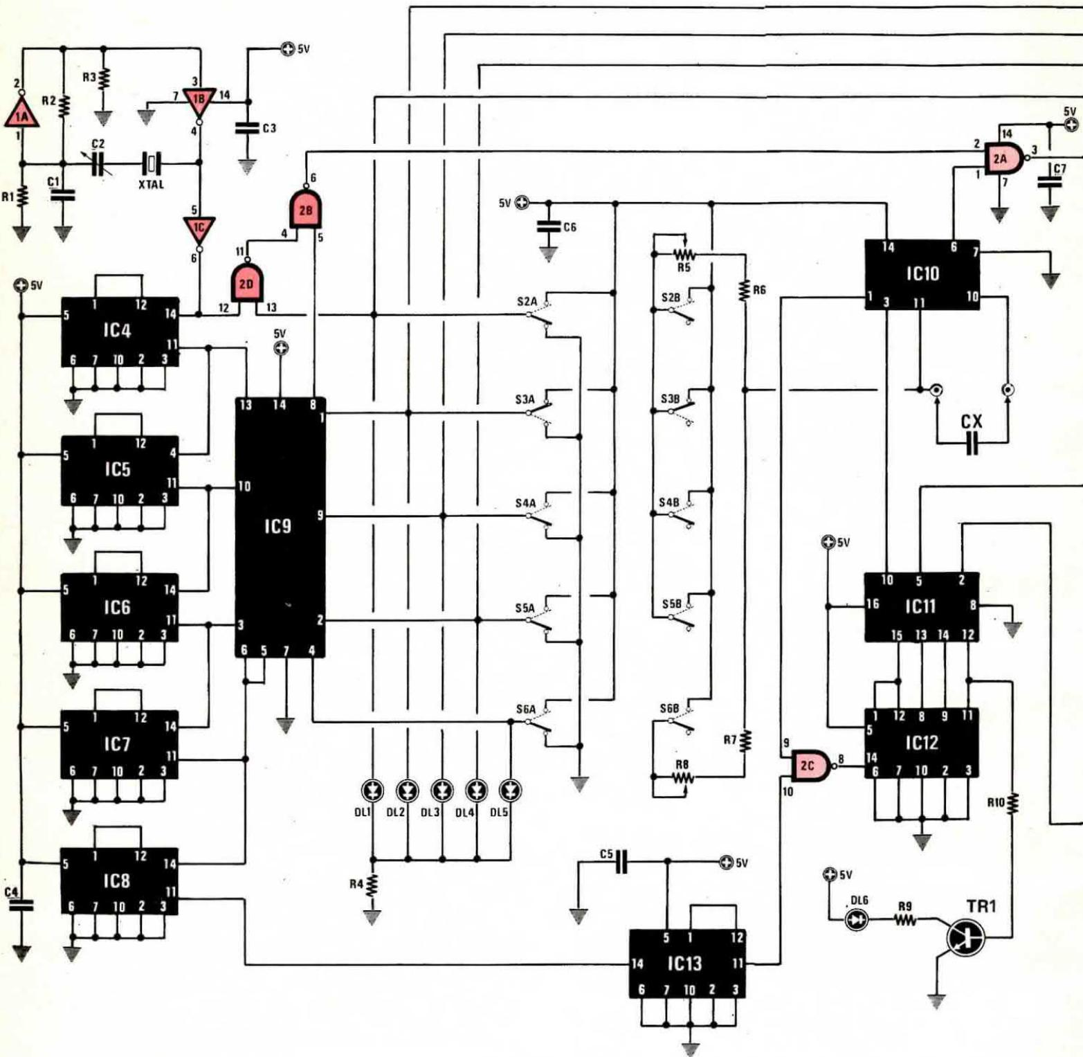
Fig. 1 Schema elettrico del capacimetro digitale con in basso il relativo alimentatore. La lista dei componenti è riportata nella pagina successiva.
