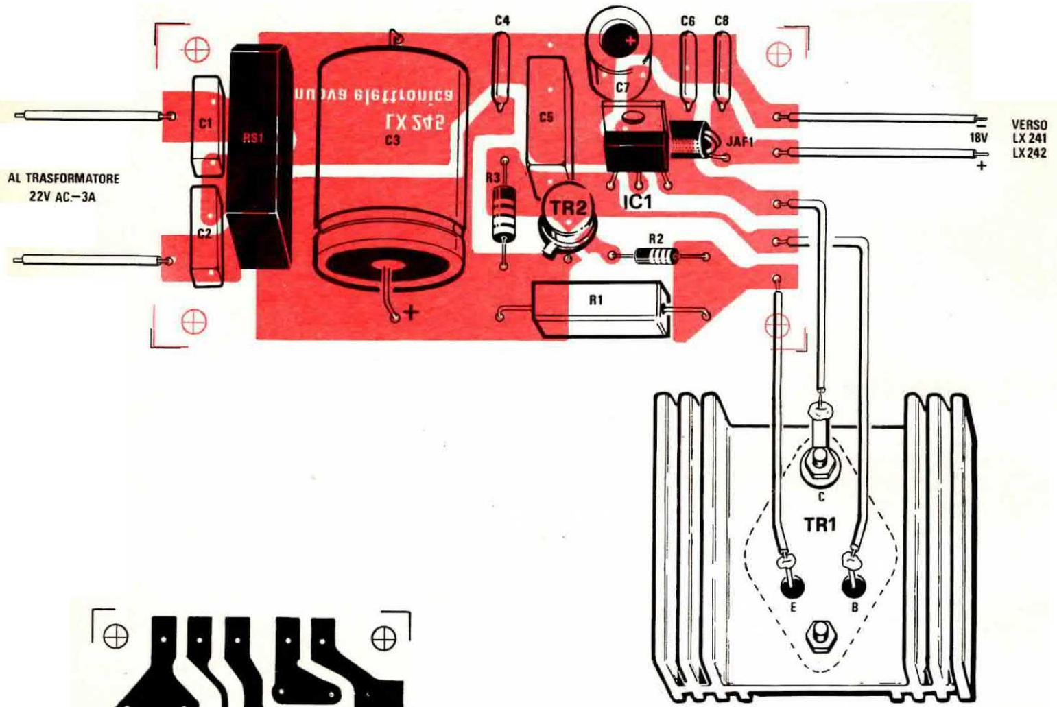
Fig. 4 Schema pratico di montaggio dell'alimentatore da 18 volt, 3 ampère. Nota: il darlington TR1 va isolato con una mica e relative rondelle dall'aletta di raffreddamento.
