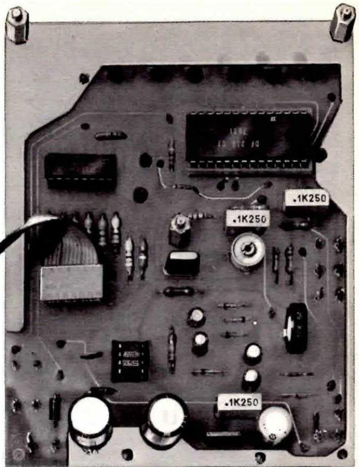
Nella foto i due telai che compongono il nostro cronometro visti separati per far vedere i componenti posti nel circuito sottostante. Si noti la piattina flessibile che congiunge i due circuiti.
