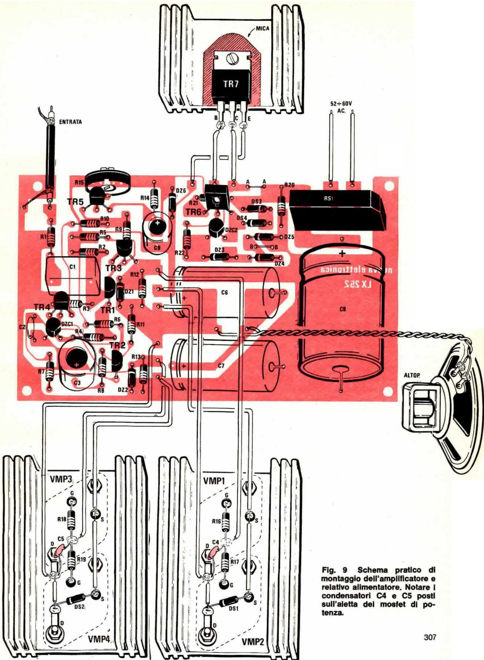
Fig. 9 Schema pratico di montaggio dell'amplificatore e relativo alimentatore. Notare i condensatori C4 e C5 posti sull'aletta dei mosfet di potenza.
