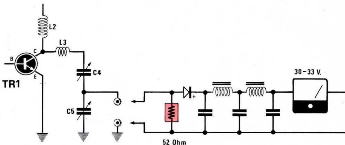
**Fig. 18** Applicando sull'uscita del lineare la sonda di potenza da 52 ohm presentata su questo stesso numero, regolando i vari compensatori, si dovrà riuscire a leggere sul tester una tensione che si aggira dai 30 ai 33 volt. Facciamo presente che man mano che la resistenza di carico si surriscalda, la tensione tenderà a diminuire.
