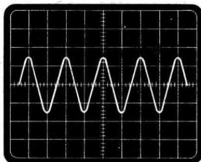
**Fig. 6** Ottenuta l'onda sinusoidale, ruotate ora il trimmer R26 in modo da ridurre l'ampiezza del segnale. Cioè da 5 quadretti, la dovremo restringere a circa 3,3 quadretti. Dovremo cioè ottenere un segnale con una ampiezza massima di 1 volt picco-picco.
