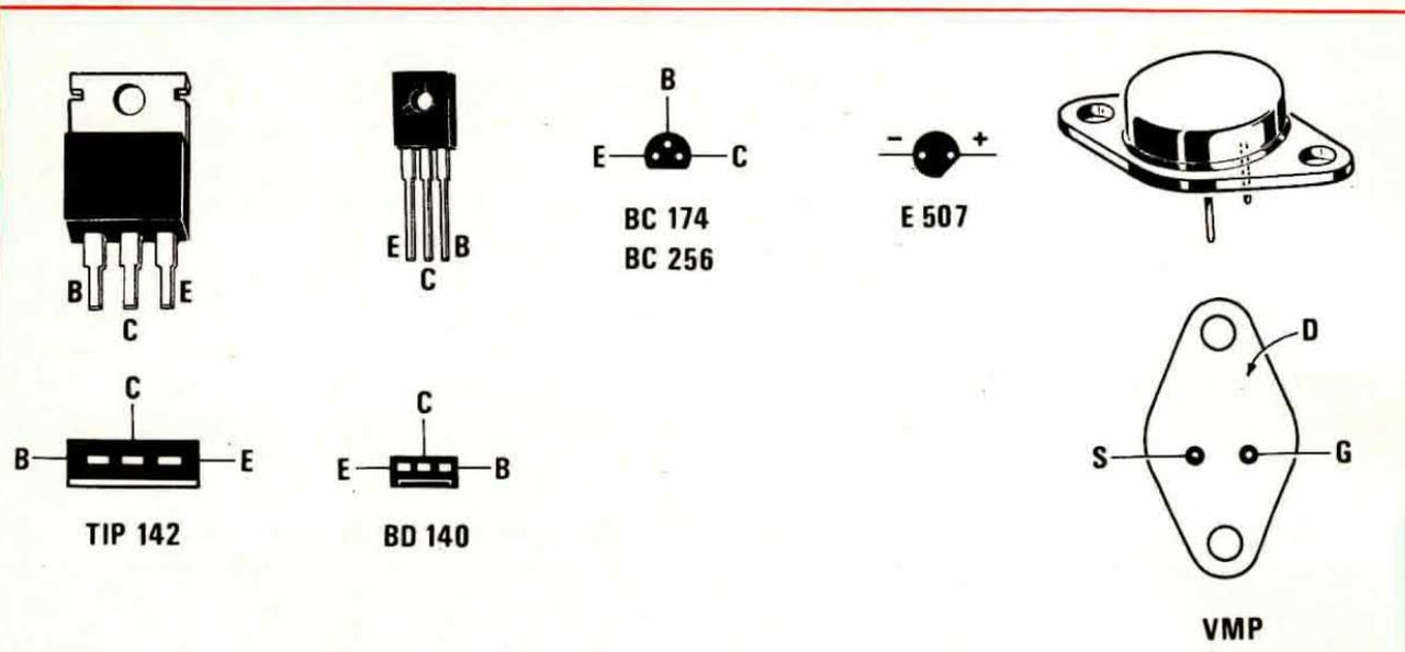
Fig. 8 Connessioni dei transistor, darlington, mosfet di potenza e dello speciale diodo zener di corrente visti da sotto.
