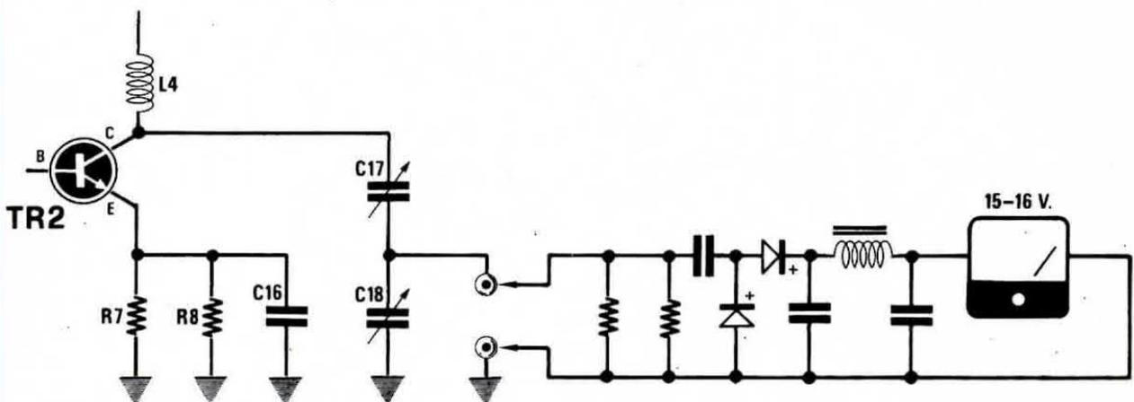
**Fig. 17** Applicando la sonda di carico (con le due resistenze da 100 ohm poste in parallelo) sull'uscita del telaio prepilota-pilota noi dovremo riuscire a ottenere, regolando i compensatori di questo stadio, una tensione di circa 15-16 volt. Se otterrete una tensione inferiore il circuito è mal tarato, o il transistor TR2-BRF36 ha un beta scarso, se troppo superiore, tal estadio innesca.
