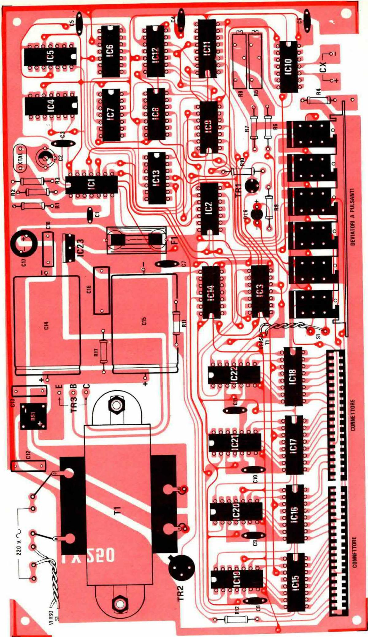
Fig. 2 (vedi sopra) Disegno a grandezza naturale del circuito stampato con sopra riportato la stampa serigrafica dei componenti.
