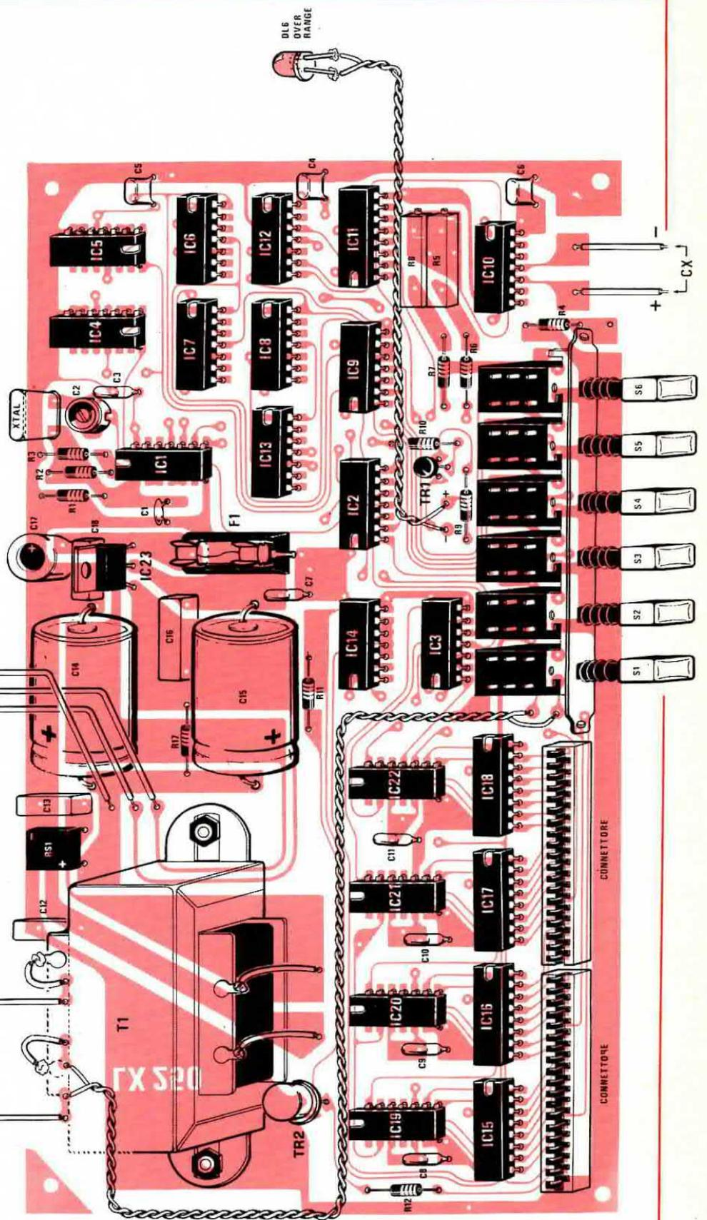
Fig. 4 Sui terminali superiori della pulsantiera salderemo i cinque diodi led che ci indicheranno di volta in volta la portata sulla quale è predisposto il capacimetro.
