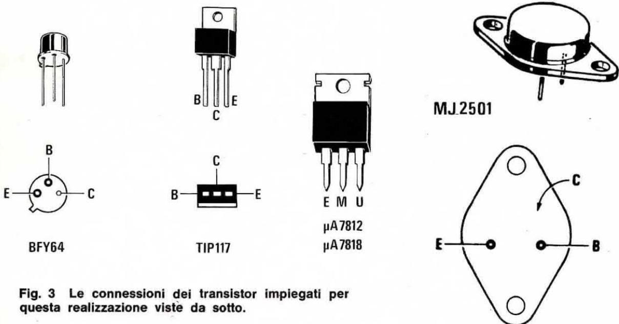
**Fig. 3** Le connessioni dei transistor impiegati per questa realizzazione viste da sotto.
