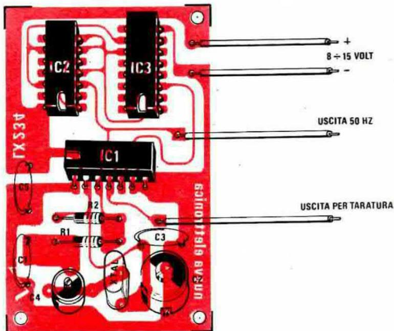
Fig. 4 Disposizione dei vari componenti sullo stampato LX234. Per gli integrati, anche se non compaiono in questo disegno, utilizzeremo i relativi zoccoli.
