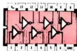
Fig. 2 In questo disegno potete notare come risultano disposti, all'interno dell'integrato SN7414, i 6 invertitori da noi utilizzati per realizzare il nostro iniettore.
