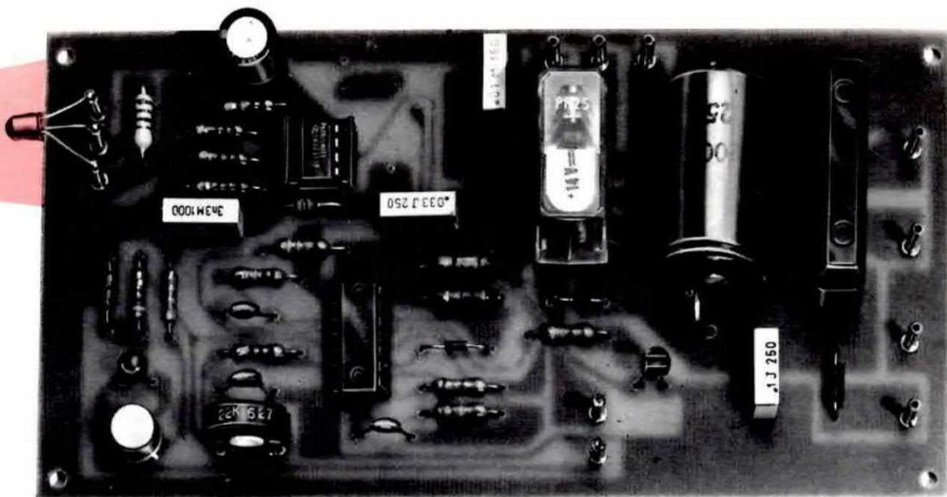
Come si presenta a costruzione ultimata il circuito dell'antifurto a raggi infrarossi. Al centro della foto si può notare il relè e sulla sinistra in alto, il fototransistor captatore. Il diodo emettitore, come spiegato nell'articolo, dovrà essere collocato di fronte al fototransistor, ad una distanza non superiore ai 3 metri.
