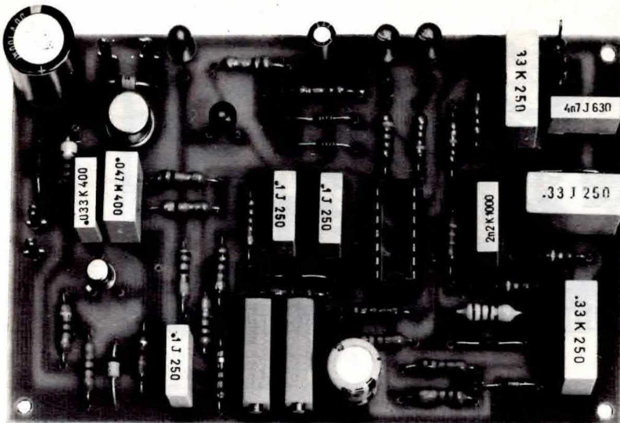
Ecco la foto di uno dei nostri prototipi di « salvamulle » da noi montati per il collaudo. Si nota in basso i due trimmer multigiri per la taratura, ed in alto i diodi led che dovremo fissare sul pannello frontale del mobile.
