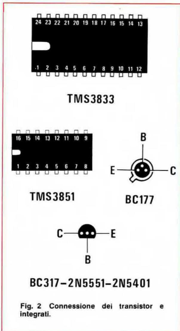
Fig. 2 Connessione dei transistor e integrati.
