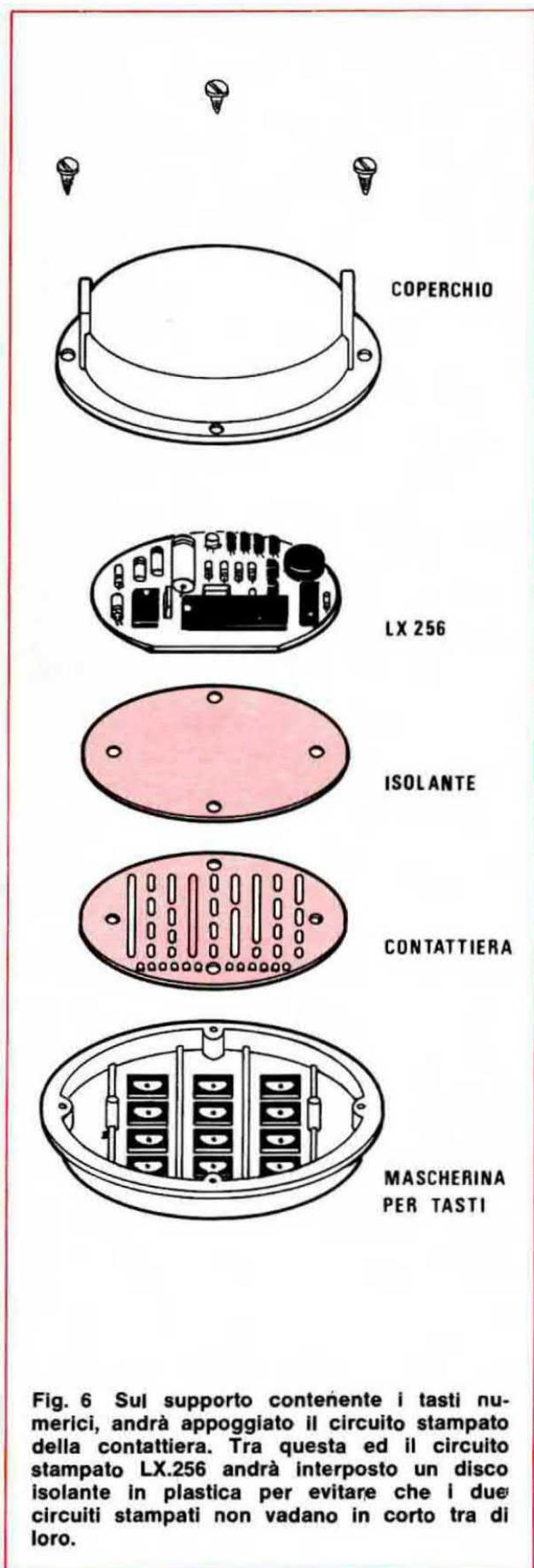
Fig. 6 Sul supporto contenente i tasti numerici, andrà appoggiato il circuito stampato della contattiera. Tra questa ed il circuito stampato LX.256 andrà interposto un disco isolante in plastica per evitare che i due circuiti stampati non vadano in corto tra di loro.
