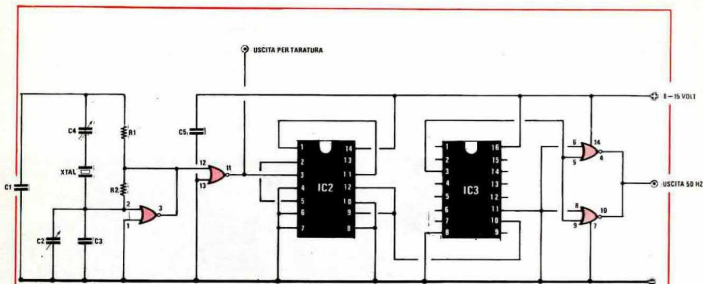
Fig. 1 Schema elettrico.
