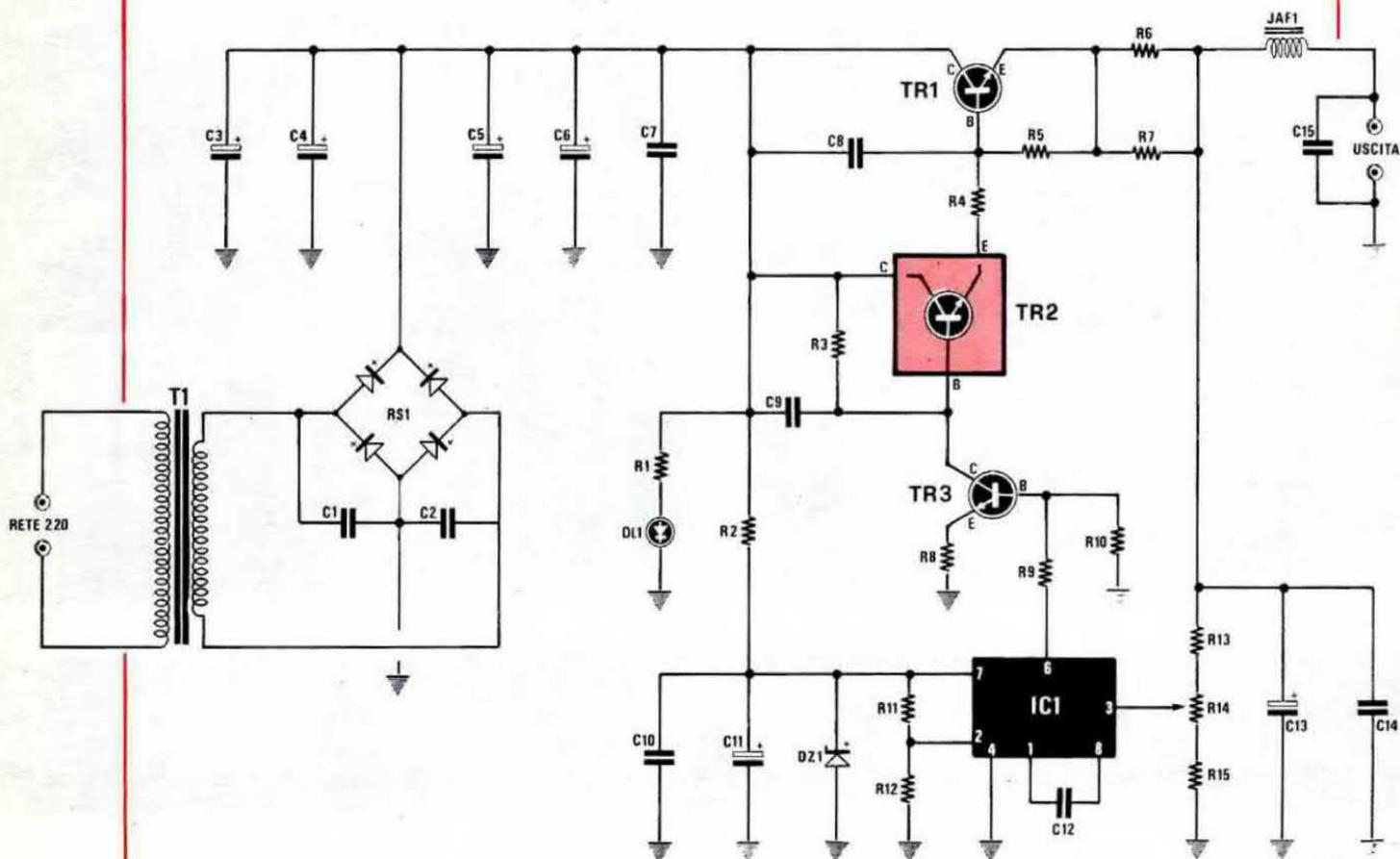
**Fig. 1** Schema elettrico dell'alimentatore.
