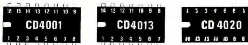
Fig. 2 Diposizione dei terminali degli integrati impiegati in questo progetto.
