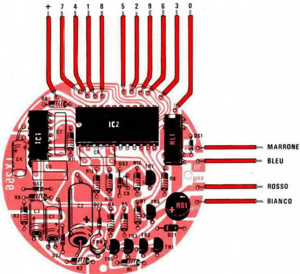
Quindi circuito stampato in fibra di vetro, già forato, con le piste di rame ricoperte da una speciale vernice protettiva che le preservi dall'umidità e da eventuali corrosioni molto frequenti soprattutto nelle zone di mare dove a causa dei sali contenuti nell'aria il rame tende spesso ad ossidarsi.
