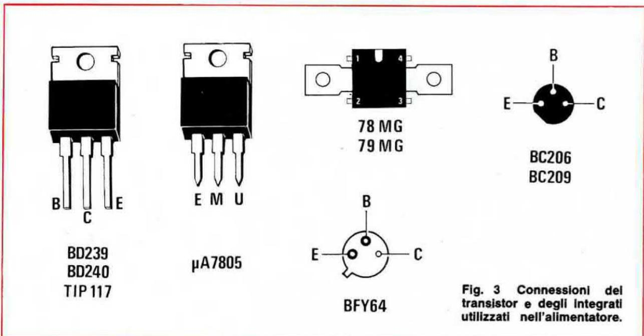
Fig. 3 Connessioni del transistor e degli integrati utilizzati nell'alimentatore.
