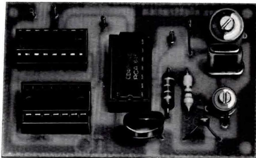
Il quarzo da 3.276.800 Hz da noi utilizzato per la realizzazione del doppio cronometro sportivo LX248, è un quarzo di tipo particolare con specifiche W10-W11, in grado cioè di garantire una altissima precisione ed una notevole stabilità in temperatura.
