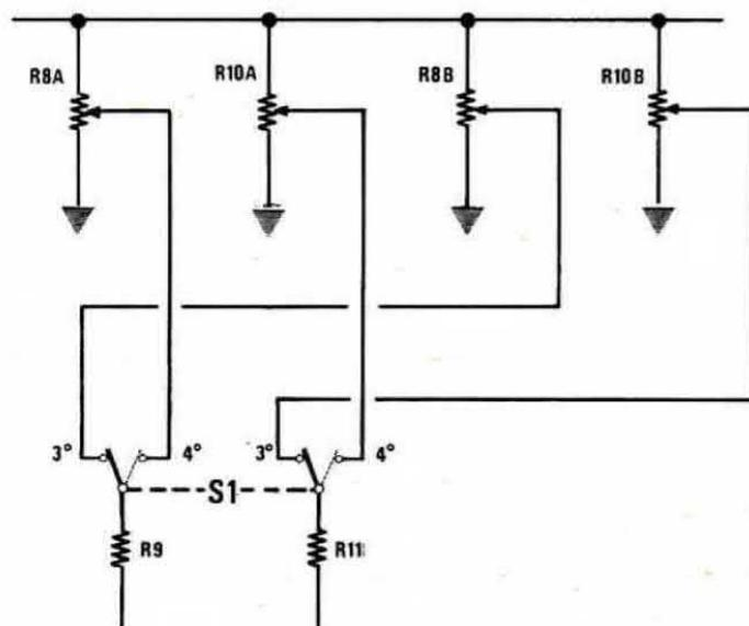
Fig. 5 È possibile adattare il nostro circuito per altre due velocità supplementare, o adottarlo per la 3ª e 4ª marcia sostituendo il deviatore S1 con un doppio deviatore e aggiungendo altre due trimmer multigiri (vedi R8B e R10B) di identico valore a R8 e R10.
