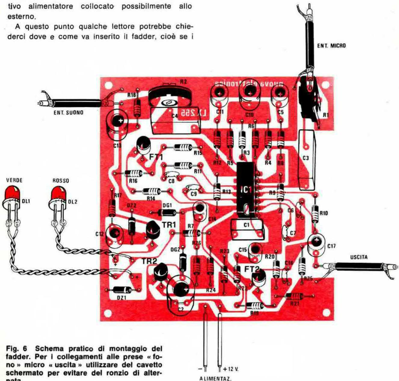
Fig. 6 Schema pratico di montaggio del fader. Per i collegamenti alle prese « fono » « micro » « uscita » utilizzare del cavetto schermato per evitare del ronzio di alternata.
