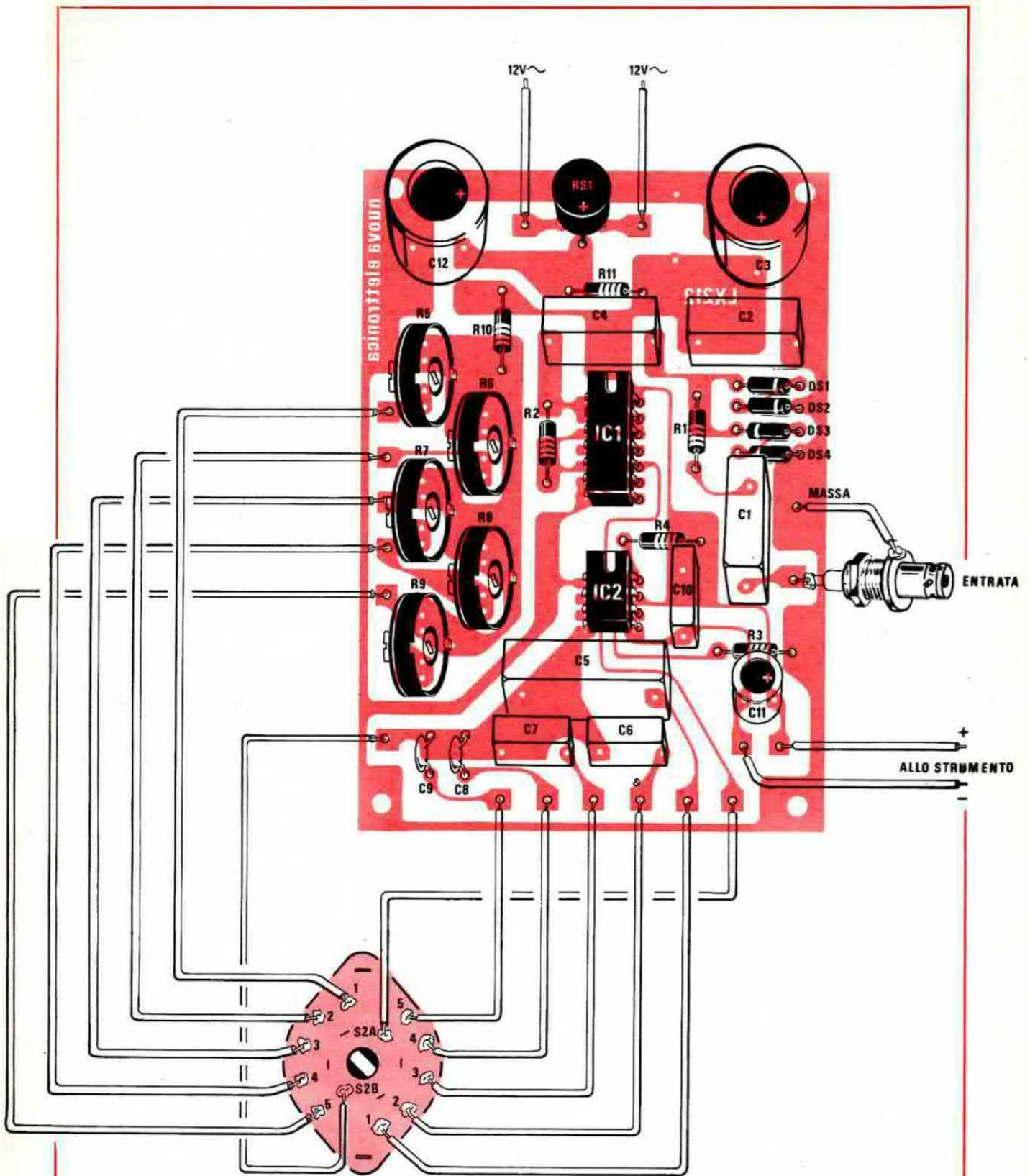
Fig. 6 Schema pratico di montaggio del frequenzimetro. Controllate prima di staginare i fili al commutatore che il cursore centrale commuti sui terminali richiesti.
