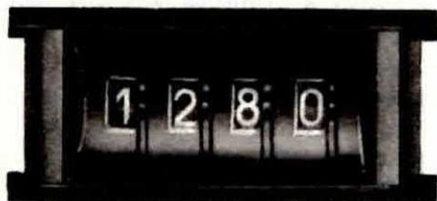
Per il nostro progetto sono necessari quattro commutatori digitali che, affiancati, ci permetteranno di ottenere un blocco a quattro cifre. Ricordatevi che i commutatori necessari per questo progetto debbono risultare del tipo BINARIO in quanto esistono anche quelli di tipo « decimale ».
