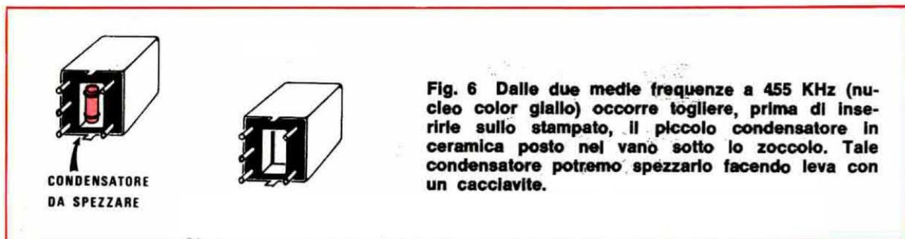
Fig. 6 Dalle due medie frequenze a 455 KHz (nucleo color giallo) occorre togliere, prima di inserirle sullo stampato, il piccolo condensatore in ceramica posto nel vano sotto lo zoccolo. Tale condensatore potremo spezzarlo facendo leva con un cacciavite.
