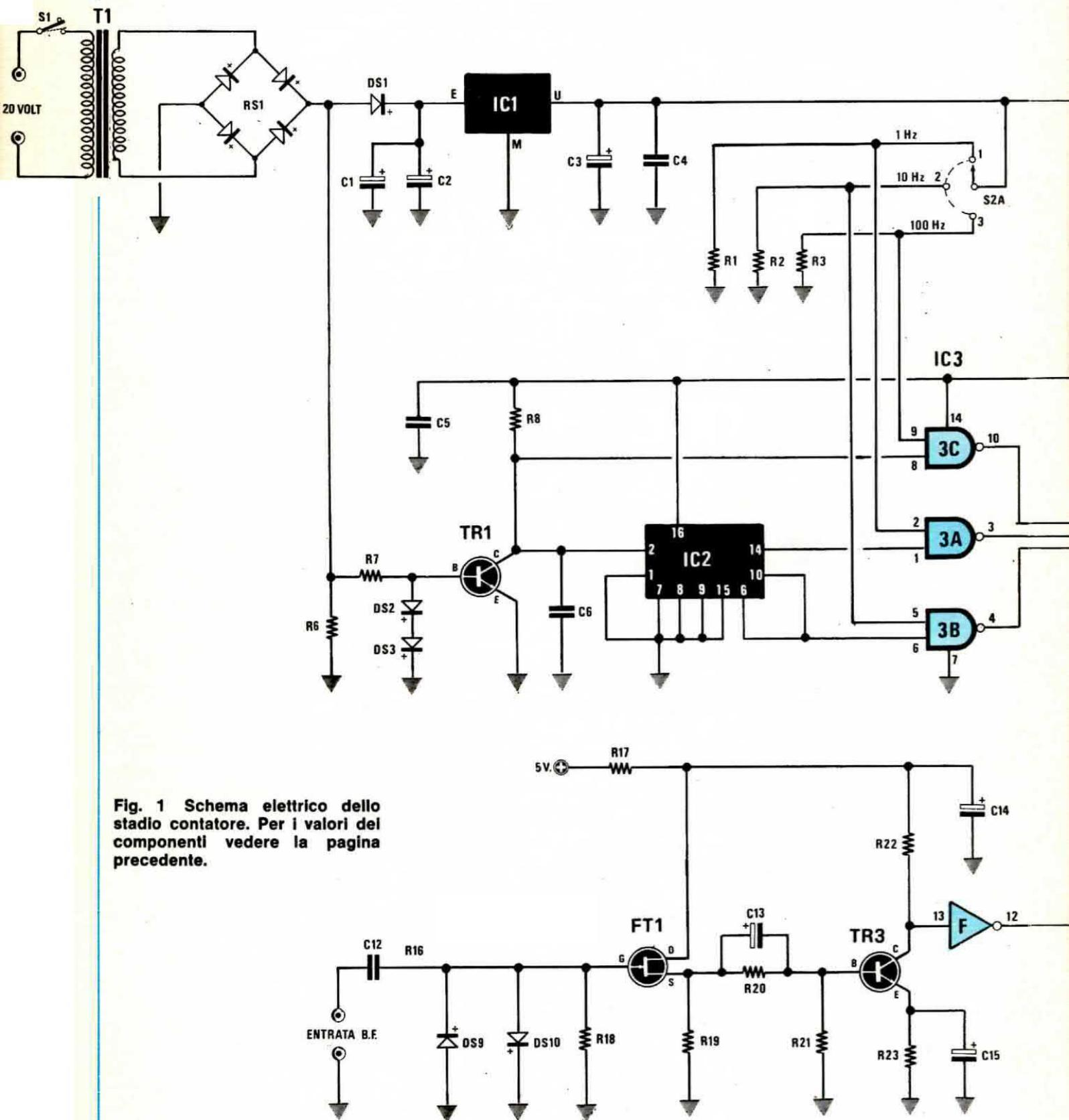
Fig. 1 Schema elettrico dello stadio contatore. Per i valori dei componenti vedere la pagina precedente.
