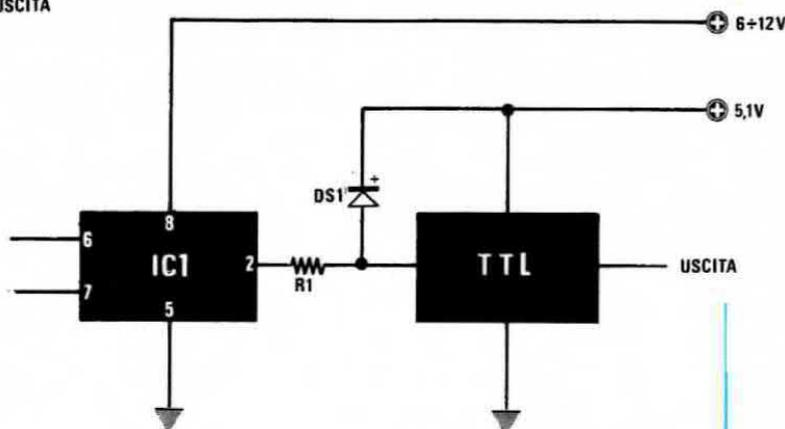
**Fig. 6** Il segnale a 50 Hz generato dall'HBF.4700 può essere applicato direttamente all'ingresso C-MOS purché entrambi gli integrati risultino alimentati dalla stessa tensione.
