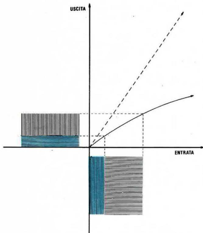
**Fig. 3 a sinistra.** La compressione viene usata in registrazione per evitare che i segnali di ampiezza troppo elevata possano saturare il nastro provocando così delle indesiderate distorsioni quando si andrà a riascoltare il pezzo.
