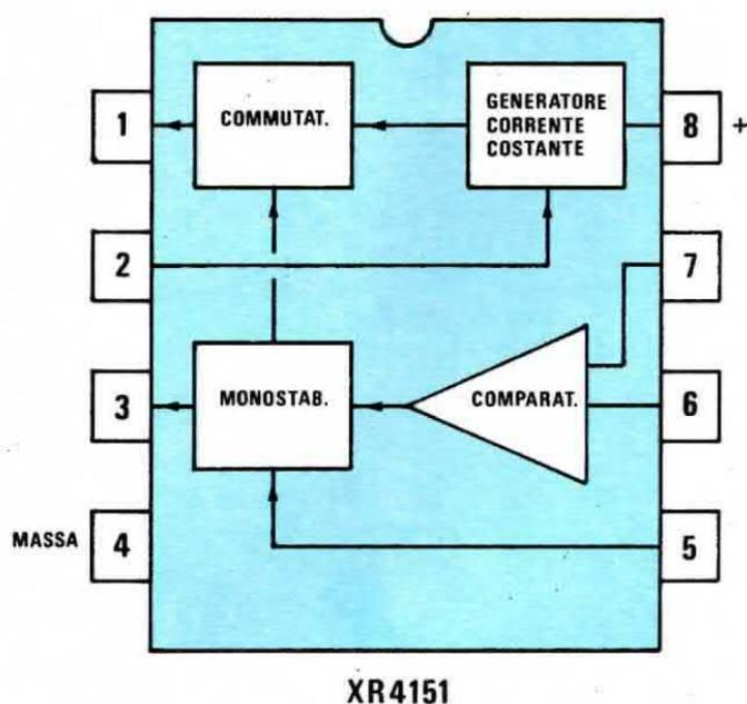
**Fig. 1** L'integrato XR.4151 pur di minuscole dimensioni (metà di un normale integrato TTL) nel suo interno contiene ben 49 transistor, 15 resistenze e 4 diodi di cui due zener collegati in modo da ottenere quattro distinti stadi in grado di convertire qualsiasi tensione compresa fra 1 millivolt e 15 volt in una frequenza compresa fra un minimo di 1 hertz ed un massimo di 15.000 Hz.
