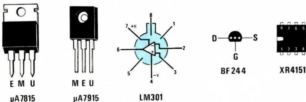
Fig. 6 Connessioni dei semiconduttori impiegati in questo progetto. Nota: L'integrato LM.301 ed il fet BF.244 sono visti da sotto, mentre l'XR.4151 da sopra. Il  $\mu$ A.7815 può avere un'involucro identico a quello indicato per l'integrato  $\mu$ A.7915 e questo ultimo identico a quello rappresentato per il  $\mu$ A.7815, quindi controllate attentamente le loro sigle prima di stagnarli sul circuito stampato in modo da non confonderli.
