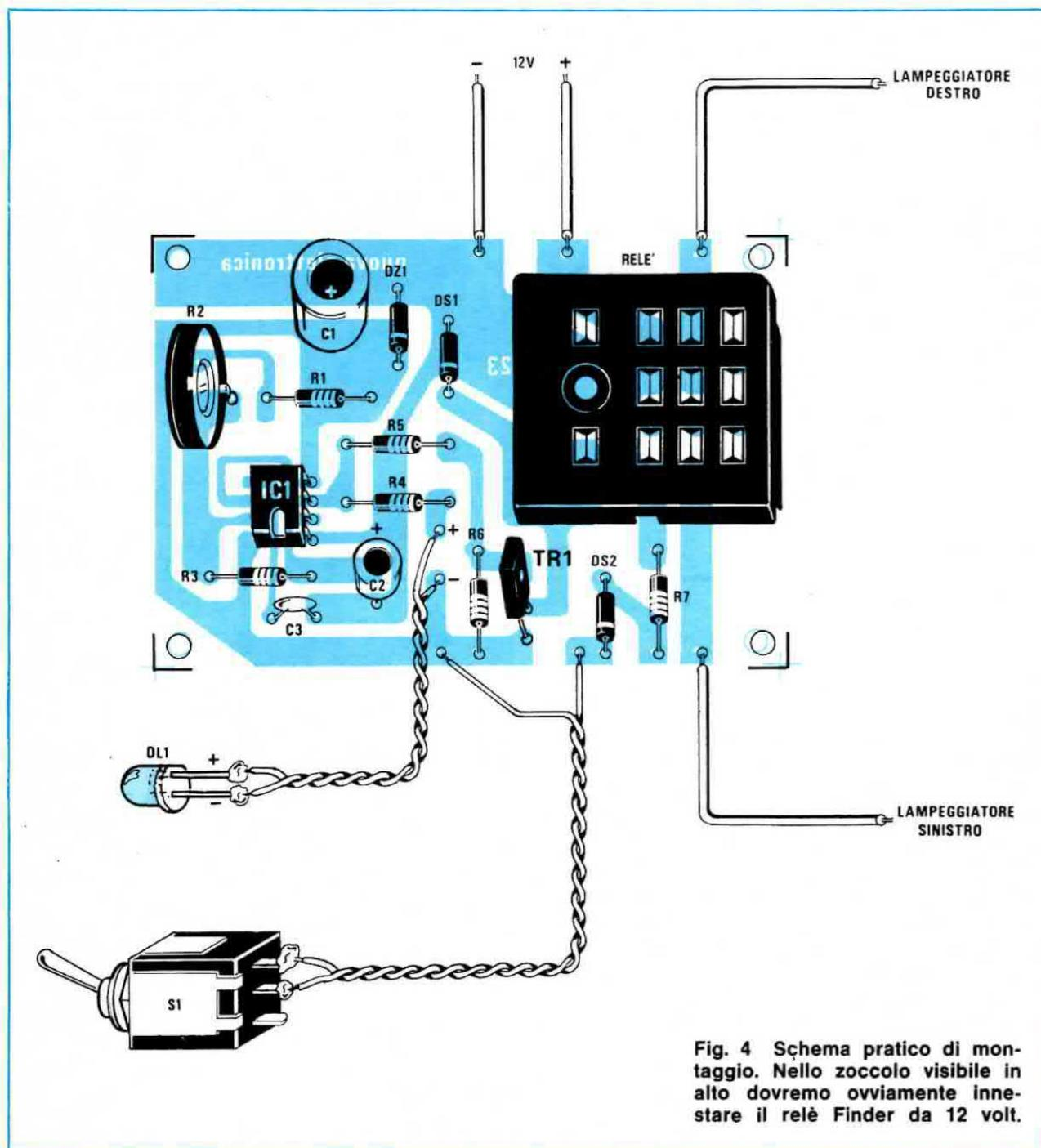
Fig. 4 Schema pratico di montaggio. Nello zoccolo visibile in alto dovremo ovviamente innestare il relè Finder da 12 volt.
