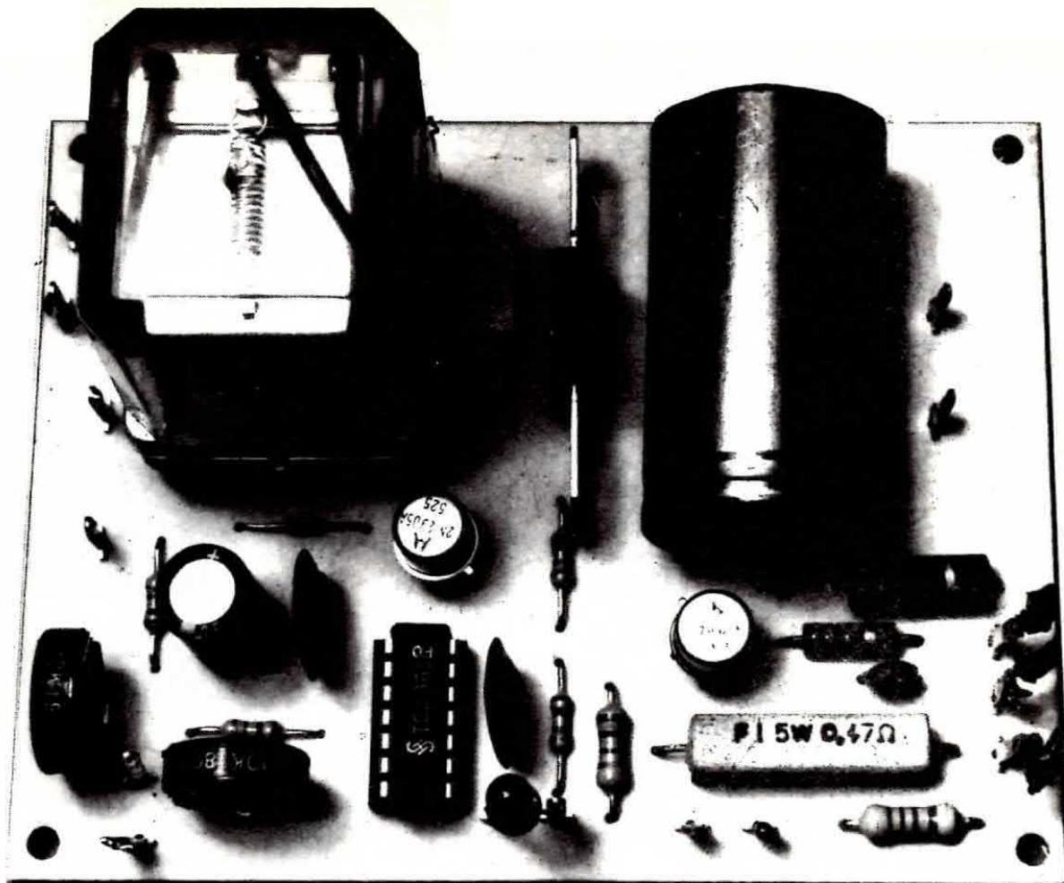
Foto del progetto montato. Si noti tra il condensatore elettrolitico e il relé il diodo al silicio di potenza 21PT20 sostituibile con altri equivalenti, purché capaci di sopportare 20 volt 7 ampère.
