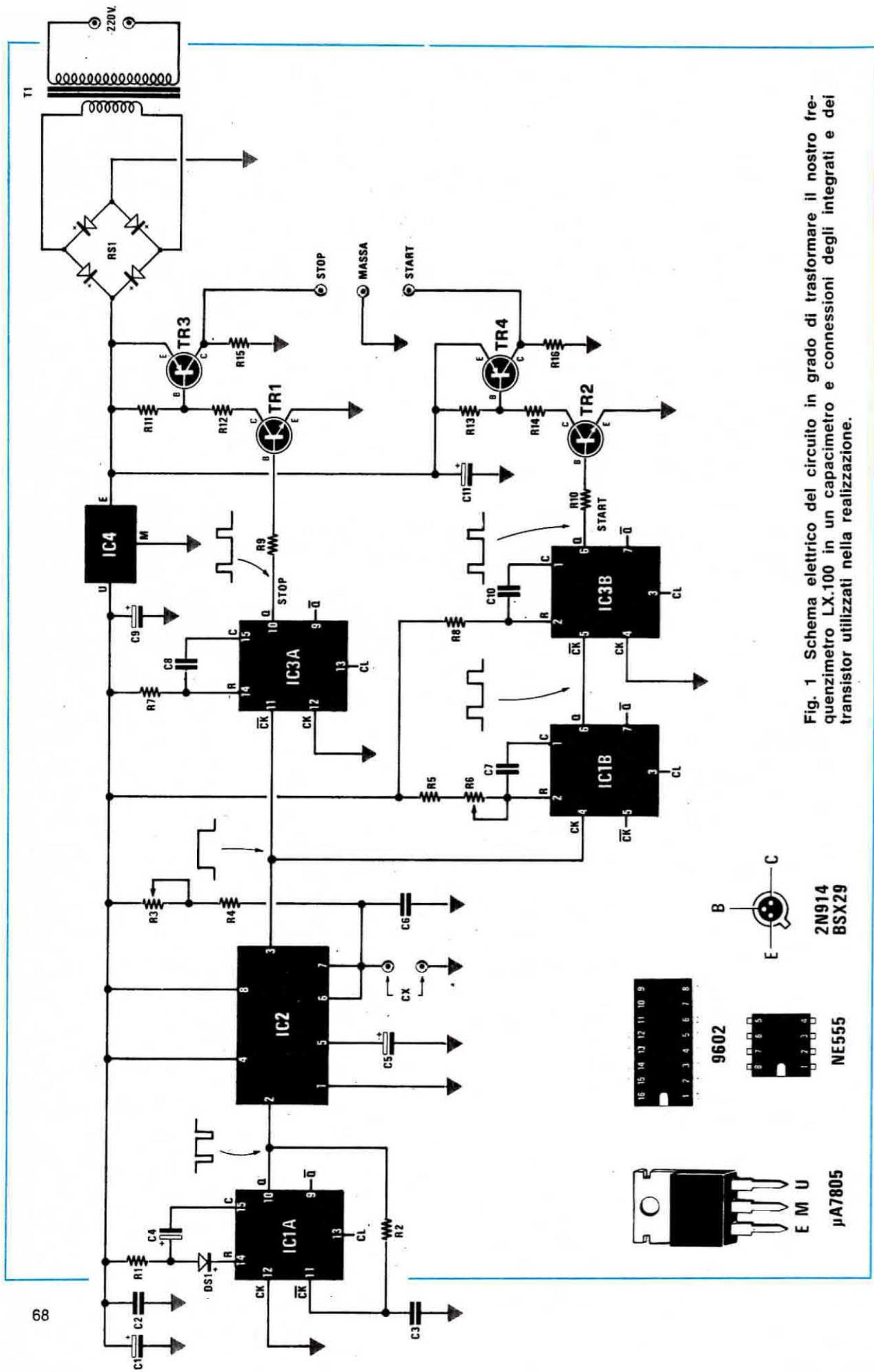
Fig. 1 Schema elettrico del circuito in grado di trasformare il nostro frequenzimetro LX.100 in un capacimetro e connessioni degli integrati e dei transistor utilizzati nella realizzazione.
