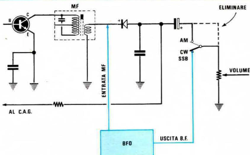
**Fig. 3** L'entrata del BFO va prelevata prima del diodo rivelatore presente nel ricevitore: l'uscita invece dovremo collegarla al potenziometro del volume, interrompendo il collegamento esistente. Un deviatore ci permetterà infine, come vedesi in disegno, di predisporre il ricevitore alla ricezione dei segnali AM oppure di quelli SSB o CW.
