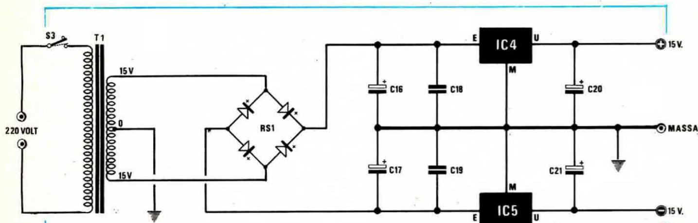
Fig. 3 Schema elettrico dell'alimentatore. Il valore dei componenti è riportato nella lista sotto la fig. 2.
