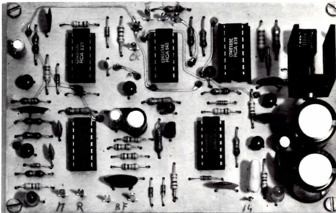
In alto sulla sinistra il circuito completo dei quattro display ad alta luminosità. L'integrato e i quattro transistor ovviamente risultano applicati dal lato opposto del circuito. Qui sopra. La foto del circuito base con tutti i componenti. Si noti l'aletta di raffreddamento applicata all'integrato IC1.
