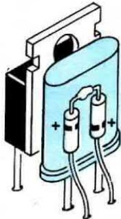
Fig. 3 Come vedesi nel disegno, la parte metallica del transistor di potenza TR1 viene appoggiata su una parete del quarzo mentre dalla parte opposta dovremo appoggiare i due diodi DS4-DS5 affinché al variare della temperatura possano modificare la tensione presente sul piedino 3 dell'integrato IC3.
