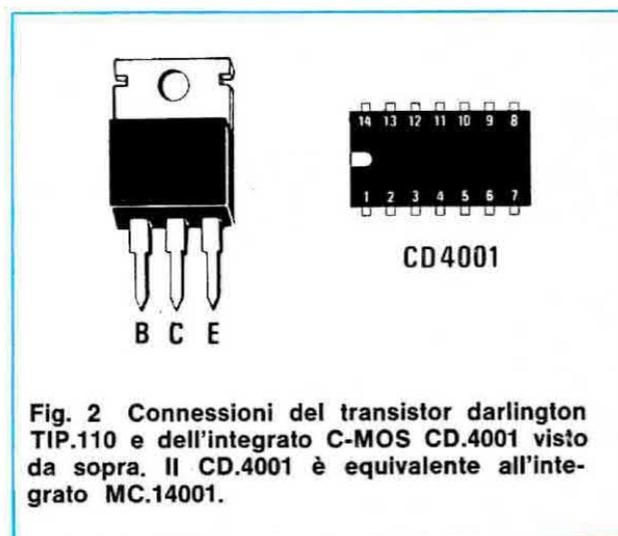
Fig. 2 Connessioni del transistor darlington TIP.110 e dell'integrato C-MOS CD.4001 visto da sopra. Il CD.4001 è equivalente all'integrato MC.14001.
