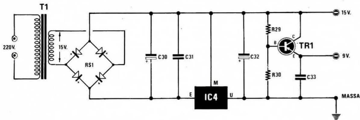
Fig. 2 Schema elettrico dell'alimentatore. Per i valori dei componenti vedere a pag. 81.
