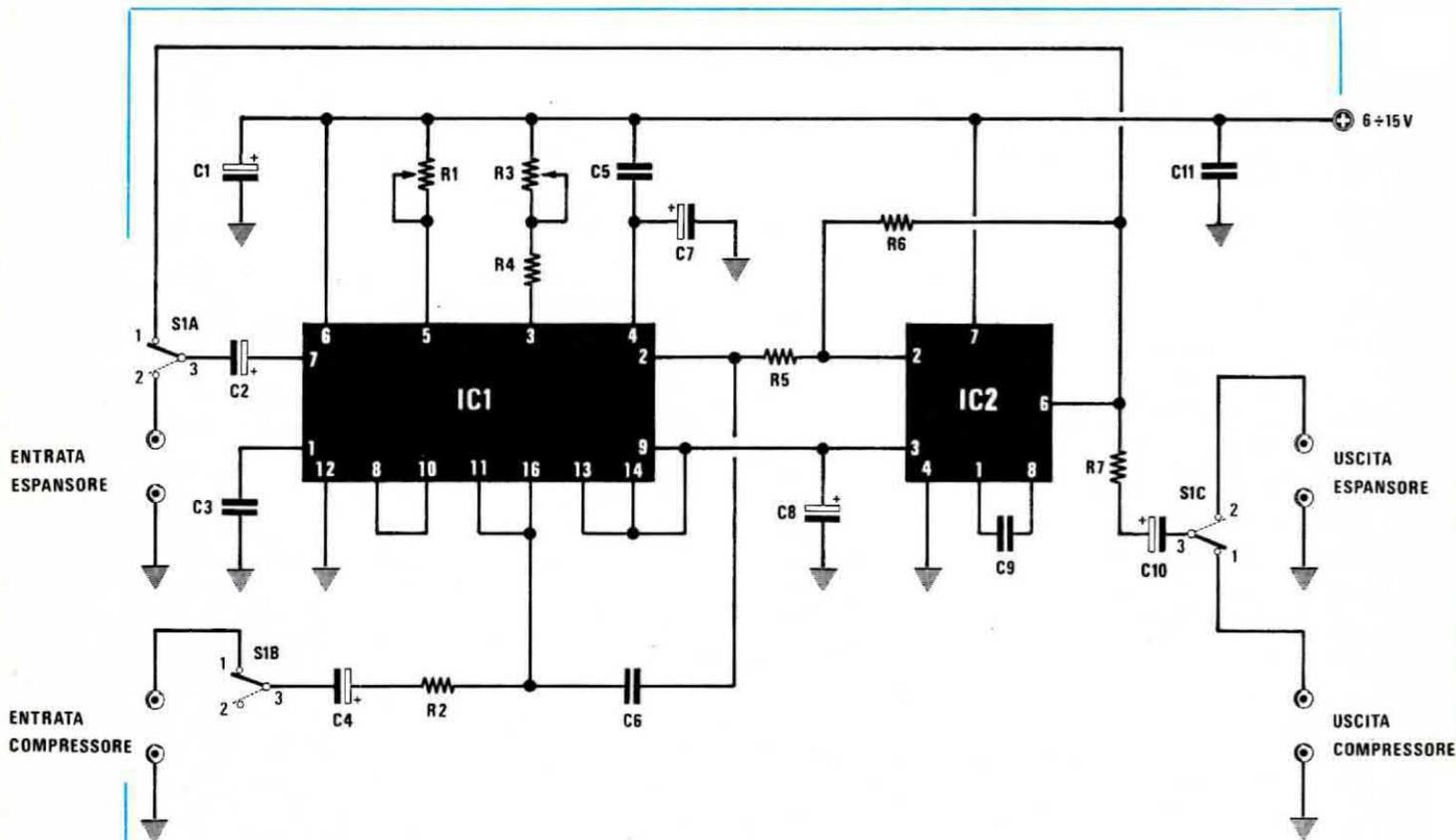
Fig. 4 Schema elettrico del compander.
