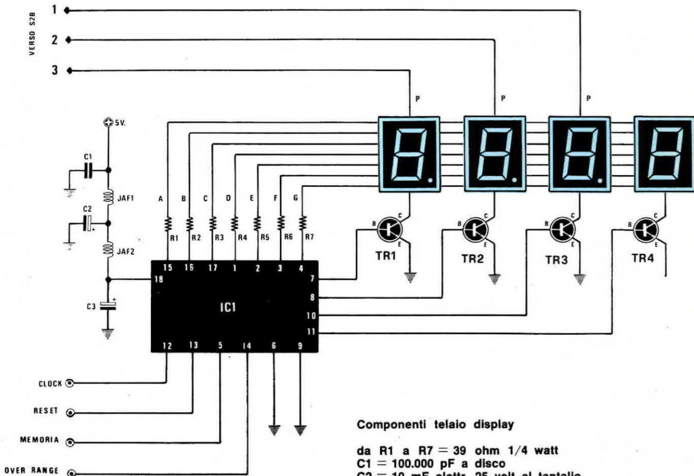
Fig. 3 Schema elettrico dello stadio visualizzatore.
