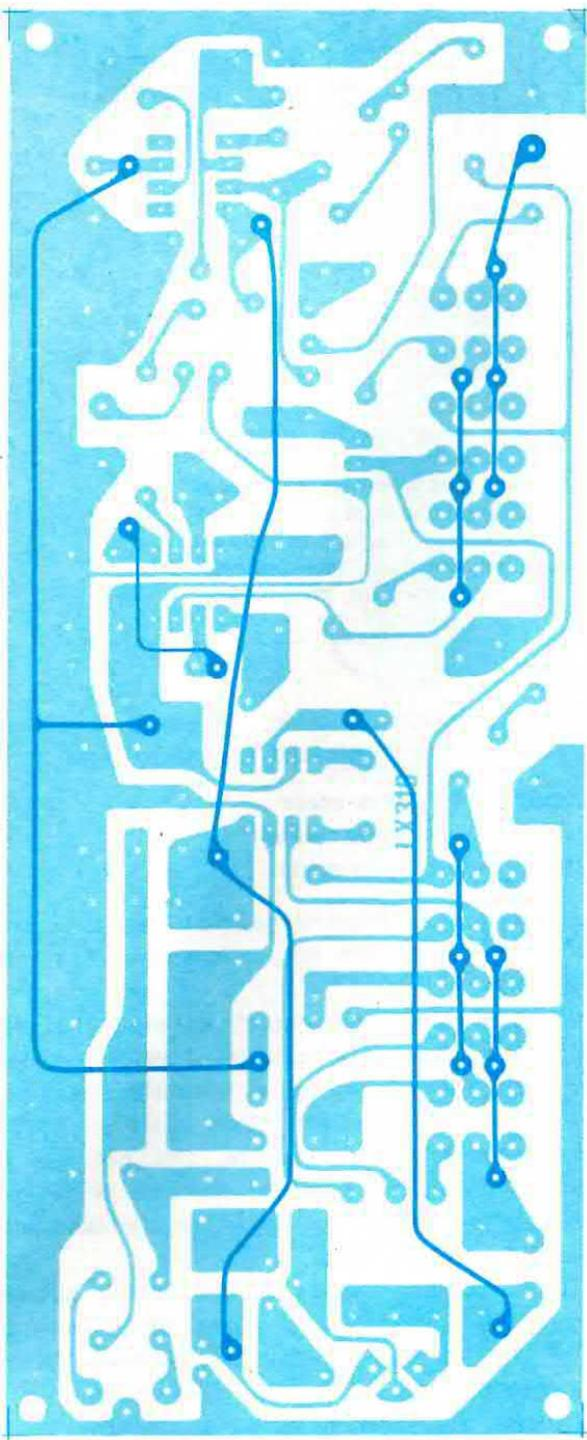
**Fig. 5** Circuito stampato a grandezza naturale. Essendo tale circuito un doppia faccia, dovremo ricordarci di collegare tramite i fori passanti le piste inferiori con quelle superiori come spiegato nell'articolo.
