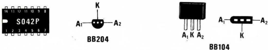
**Fig. 2** Connessioni dell'Integrato SO.42 P visto da sopra e del doppio diodo varicap BB.104 o BB.204 visto da sotto. **NOTA.** Il BB.104 è identico come caratteristiche al BB.204: unica differenza è, come vedesi in figura, il tipo di involucro.
