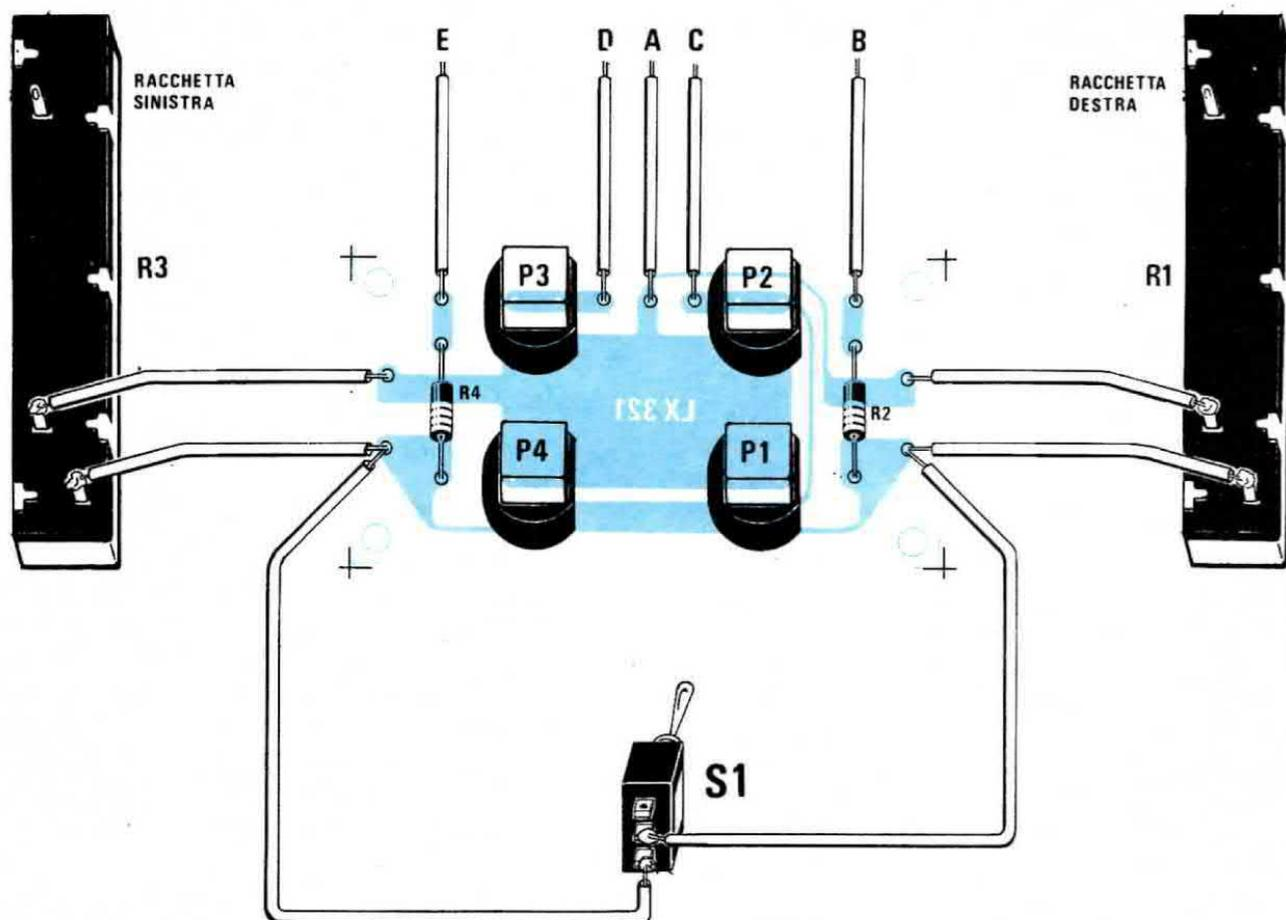
**Fig. 7** Sul circuito stampato LX.321 troveranno posto i quattro pulsanti di commutazione. A tale circuito dovremo collegare i due potenziometri slider e l'interruttore S1. I fili E-D-A-C-B andranno collegati al circuito stampato visibile in fig. 6.
