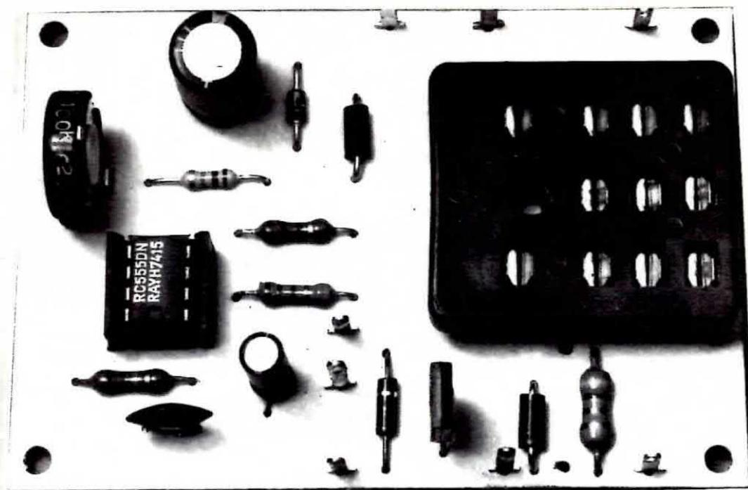
Il circuito, come vedesi in fig. 1, è molto semplice e si compone in pratica di un integrato NE.555 impiegato come oscillatore a bassissima frequenza il quale pilota con la sua uscita (piedino 3) un transistor PNP di tipo BD.140.
