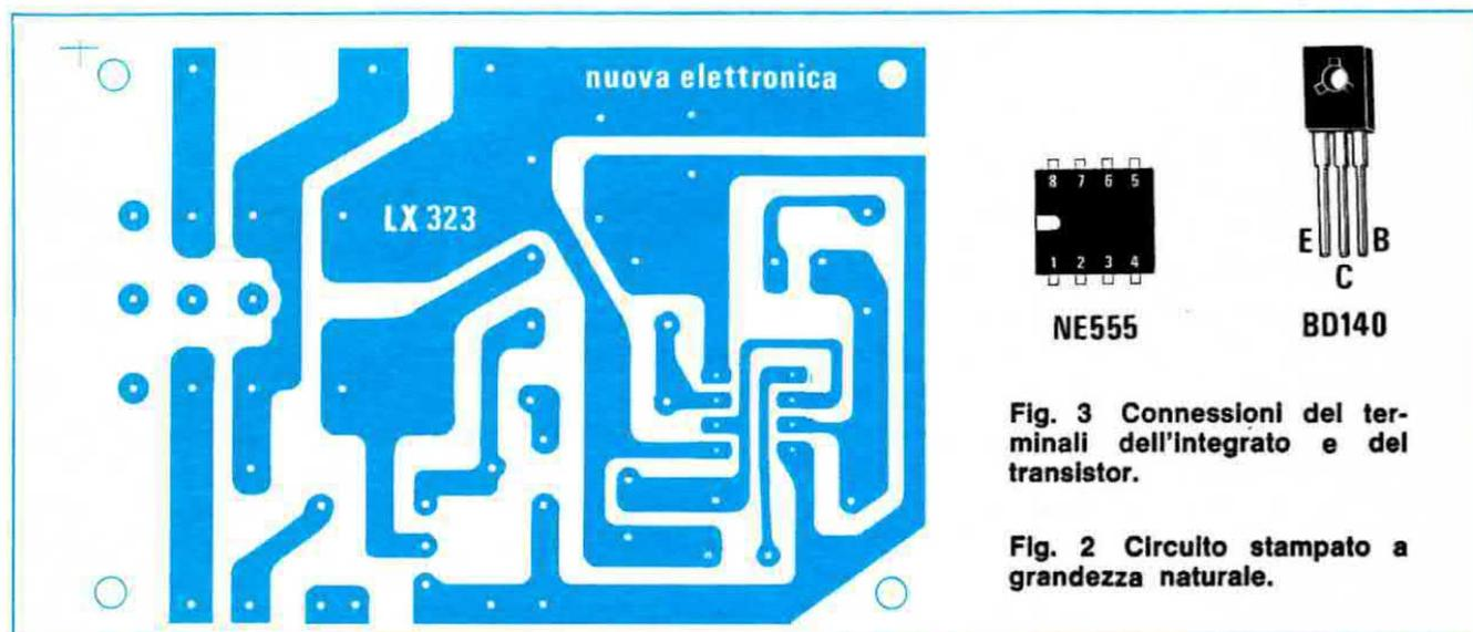
Fig. 3 Connessioni dei terminali dell'integrato e del transistor.
