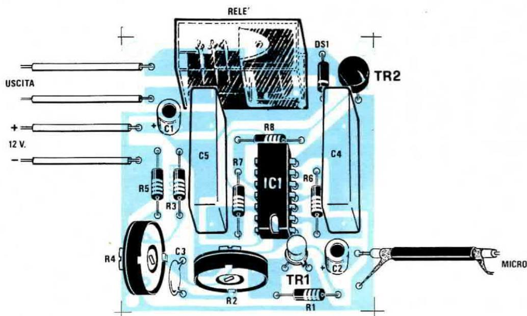
Fig. 4 Schema pratico di montaggio del relé microfonico.
