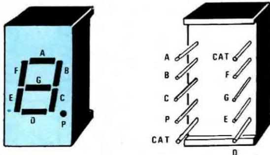
Fig. 2 Nel disegno è possibile vedere a quali terminali del display LT.302 corrispondono i vari segmenti A-B-C-D-E-F-G. Il terminale P è quello relativo al punto ed i due indicati CAT sono i catodi comuni che andranno a collegarsi ai collettori dei transistor.
