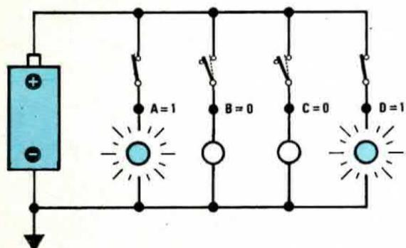
Fig. 1 In linguaggio digitale, quando si parla di « condizione logica 1 », si intende presenza di una tensione positiva, mentre con « condizione logica 0 » si intende assenza di tensione. In questa figura quindi i terminali A - D sono in condizione logica 1 (lampade accese) mentre B e C in condizione logica 0.
