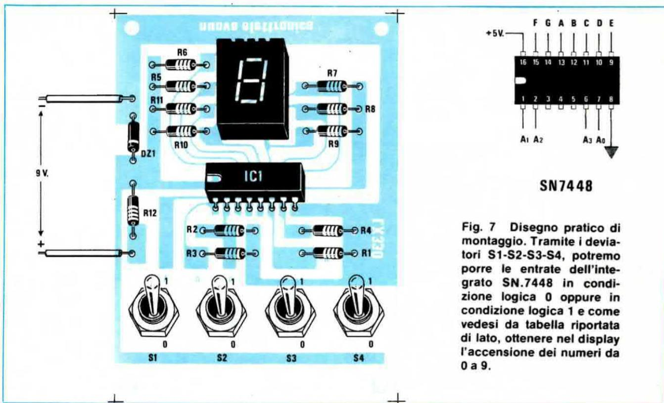
Fig. 7 Disegno pratico di montaggio. Tramite i deviatori S1-S2-S3-S4, potremo porre le entrate dell'integrato SN.7448 in condizione logica 0 oppure in condizione logica 1 e come vedesi da tabella riportata di lato, ottenere nel display l'accensione dei numeri da 0 a 9.
