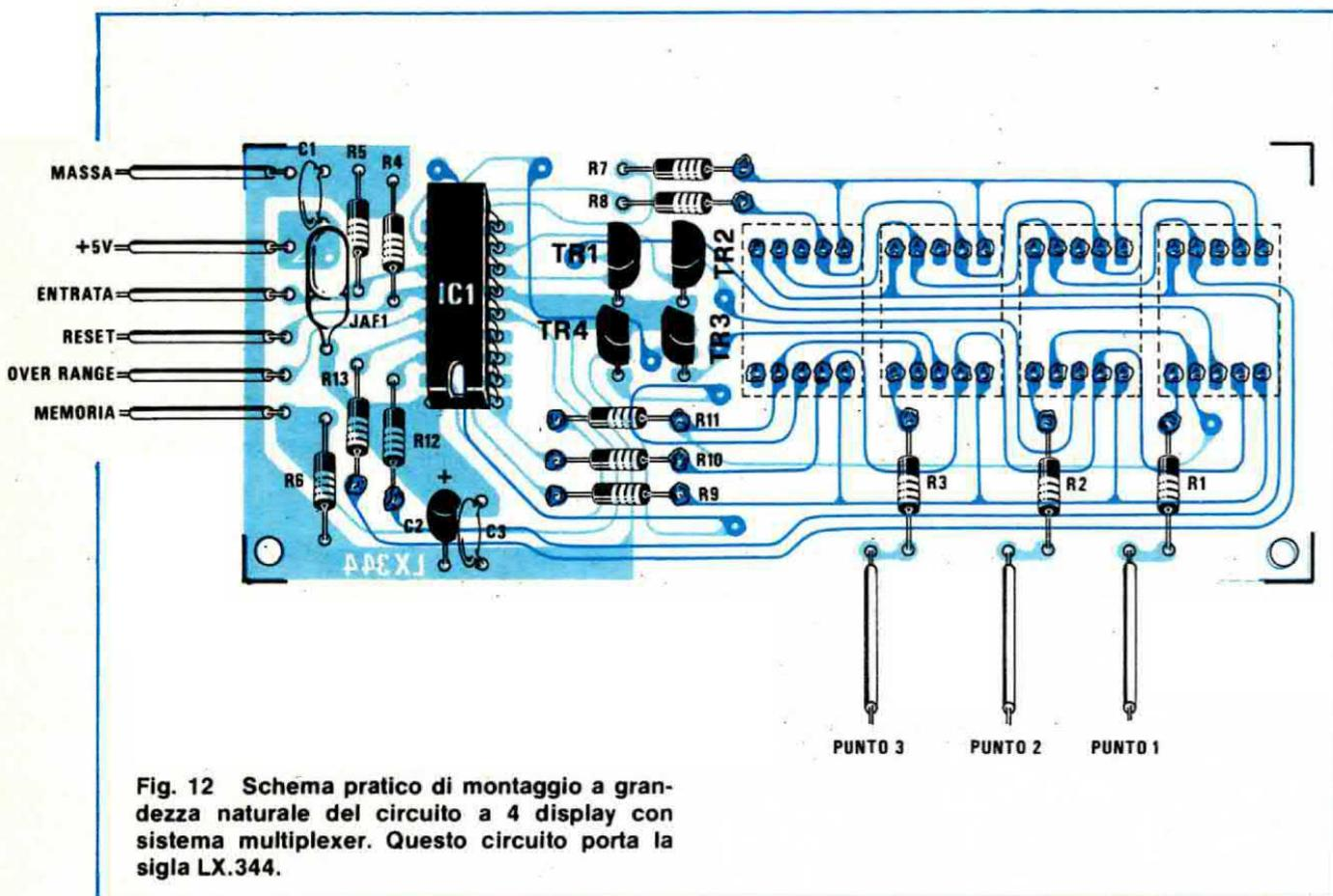
Fig. 12 Schema pratico di montaggio a grandezza naturale del circuito a 4 display con sistema multiplexer. Questo circuito porta la sigla LX.344.
