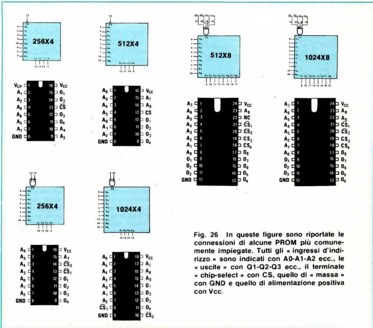
Fig. 26 In queste figure sono riportate le connessioni di alcune PROM più comunemente impiegate. Tutti gli « ingressi d'indirizzo » sono indicati con A0-A1-A2 ecc., le « uscite » con Q1-Q2-Q3 ecc., il terminale « chip-select » con CS, quello di « massa » con GND e quello di alimentazione positiva con Vcc.
