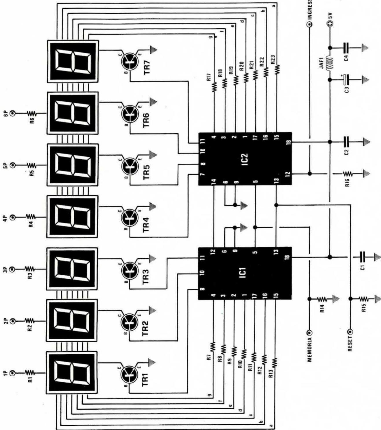
**Fig. 6** Schema elettrico del nostro contatore a sette cifre con sistema multiplexer.
