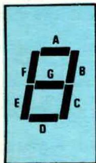
Fig. 3 In un display noi abbiamo sette diodi led a forma di segmento disposti in modo da formare un 8. Accendendo questi segmenti secondo opportune combinazioni noi possiamo ottenere tutti i numeri compresi tra lo 0 e il 9.
