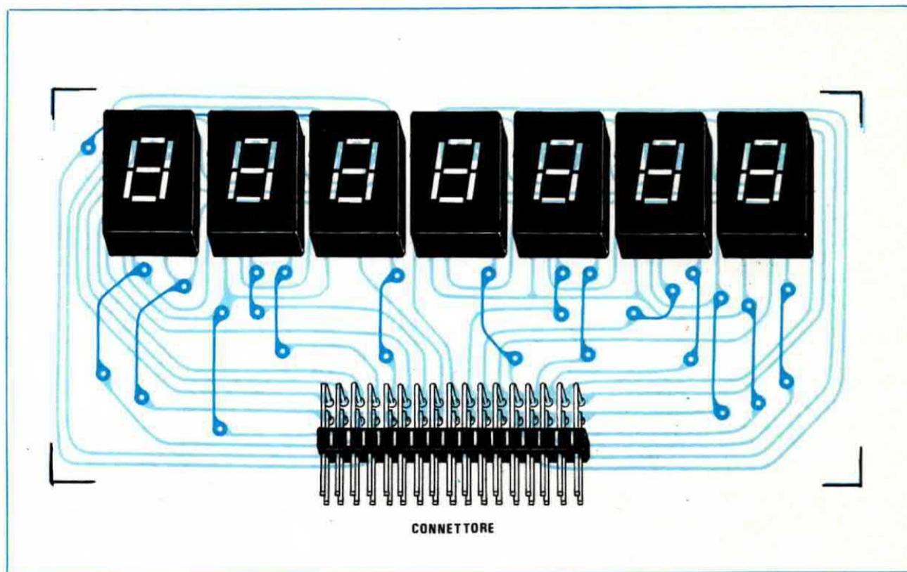
Fig. 13 Schema pratico di montaggio riportato a grandezza naturale del telaio per sette display che andrà innestato nel circuito di fig. 14. Questo circuito porta la sigla LX.347.D.
