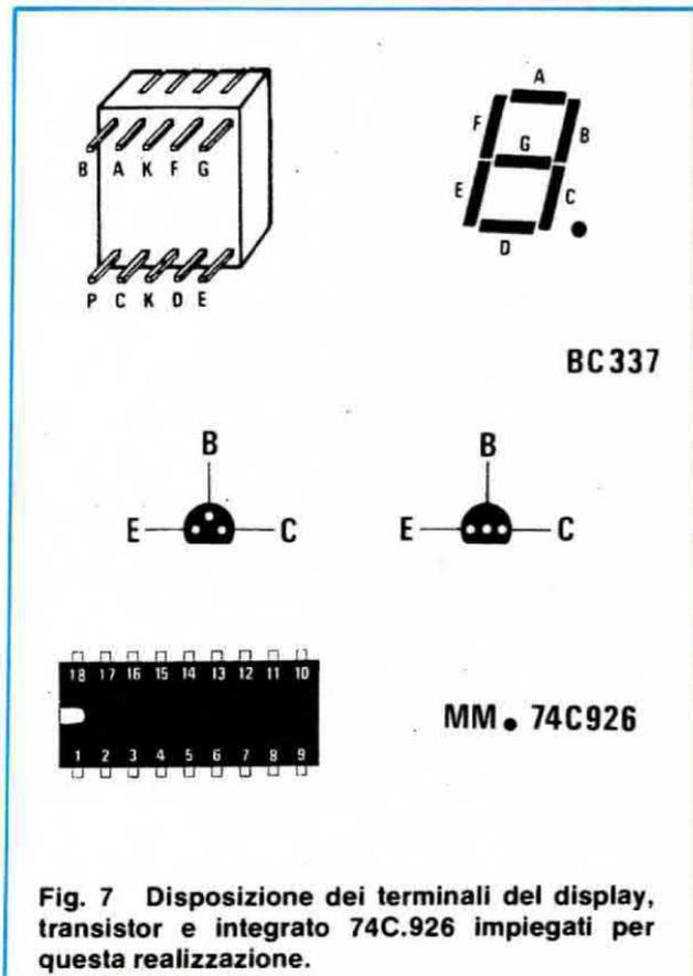
Fig. 7 Disposizione dei terminali del display, transistor e integrato 74C.926 impiegati per questa realizzazione.
