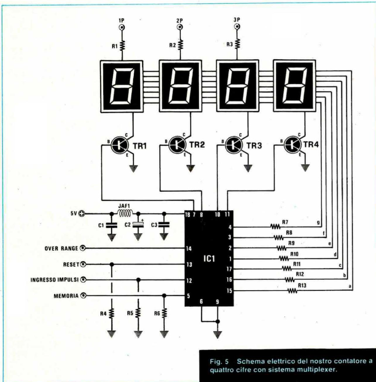
Fig. 5 Schema elettrico del nostro contatore a quattro cifre con sistema multiplexer.
