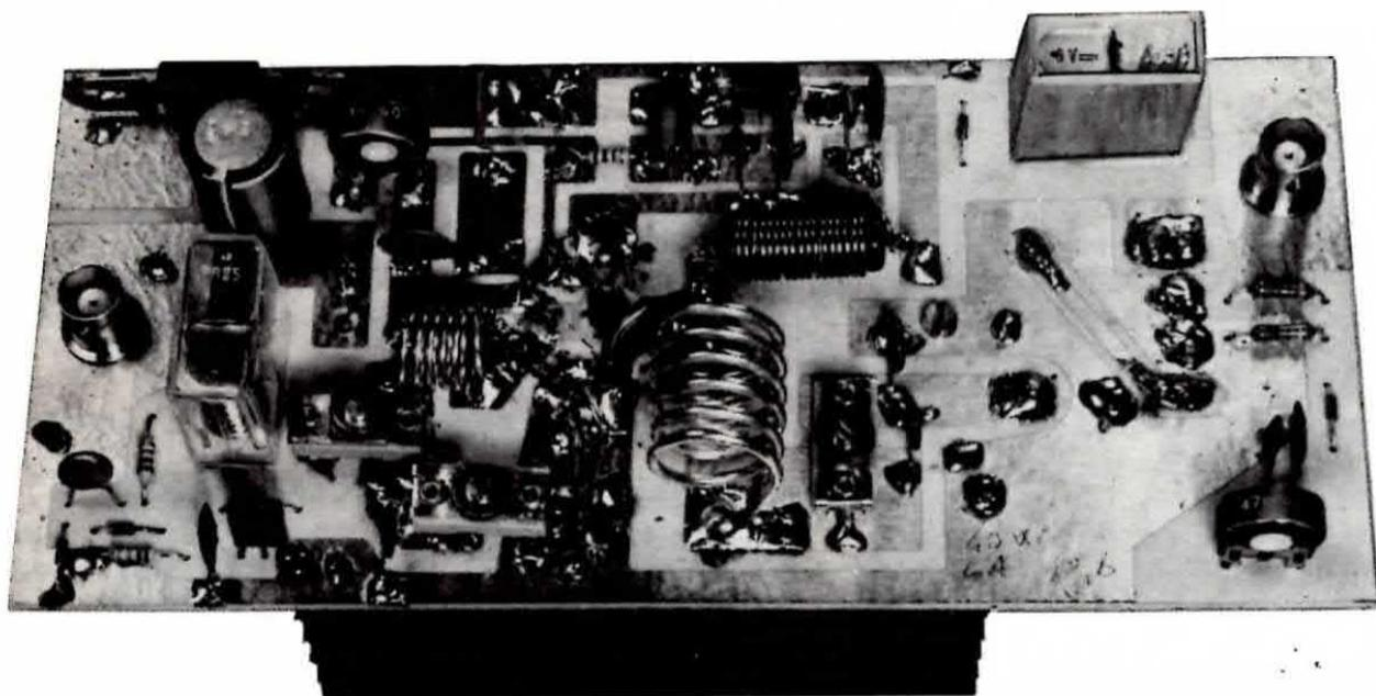
In questa foto è visibile il lineare già montato visto da sopra. Si notino le due bobine di accordo, la L2 avvolta sopra alla resistenza R7 ed il diodo di potenza DS7 necessario per salvaguardare il transistor dai picchi negativi presenti nell'impianto di alimentazione di una vettura in moto.
