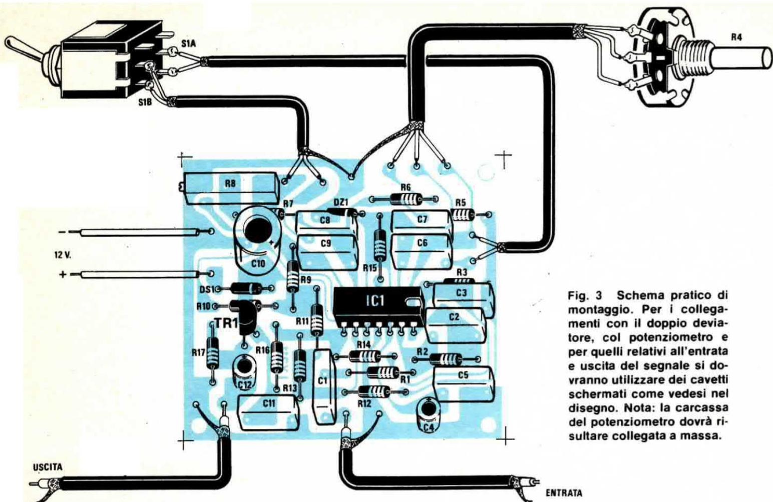
Fig. 3 Schema pratico di montaggio. Per i collegamenti con il doppio deviatore, col potenziometro e per quelli relativi all'entrata e uscita del segnale si dovranno utilizzare dei cavetti schermati come vedesi nel disegno. Nota: la carcassa del potenziometro dovrà risultare collegata a massa.
