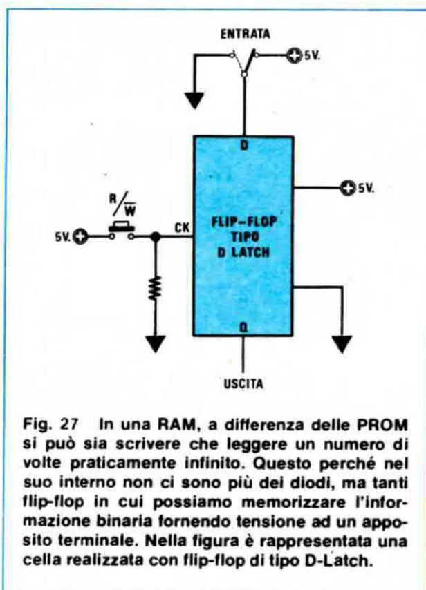
Fig. 27 In una RAM, a differenza delle PROM si può sia scrivere che leggere un numero di volte praticamente infinito. Questo perché nel suo interno non ci sono più dei diodi, ma tanti flip-flop in cui possiamo memorizzare l'informazione binaria fornendo tensione ad un apposito terminale. Nella figura è rappresentata una cella realizzata con flip-flop di tipo D-Latch.
