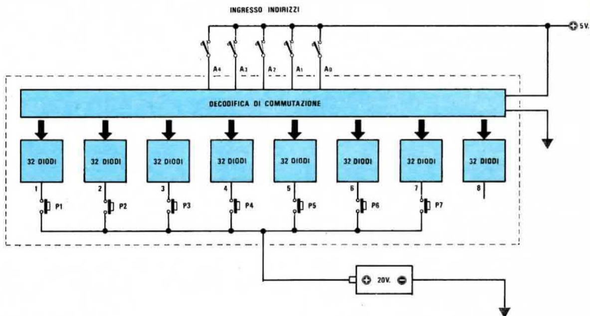
Fig. 24 Teoricamente, per « bruciare » i diodi contenuti nelle 7 celle (la 8ª cella rimane inutilizzata) sarebbe sufficiente applicare sulle uscite dei pulsanti pigiando solo quelli relativi alle celle interessate. In pratica, come già accennato nell'articolo, per bruciare i diodi, occorre un apposito circuito in grado di fornire degli impulsi della durata di circa 200 microsecondi diversamente ricorre il rischio di danneggiare la PROM.
