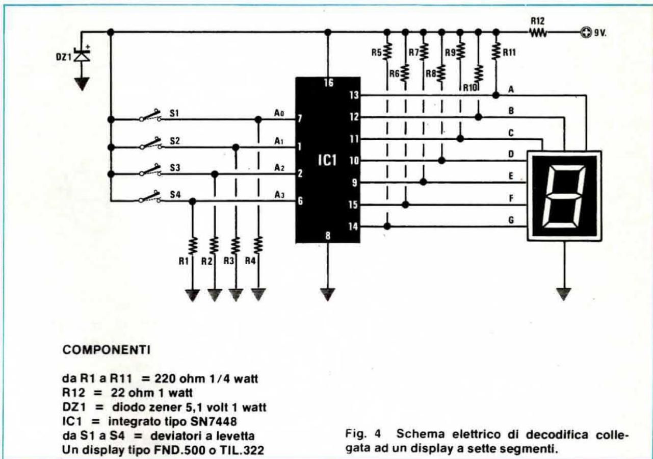
Fig. 4 Schema elettrico di decodifica collegata ad un display a sette segmenti.
