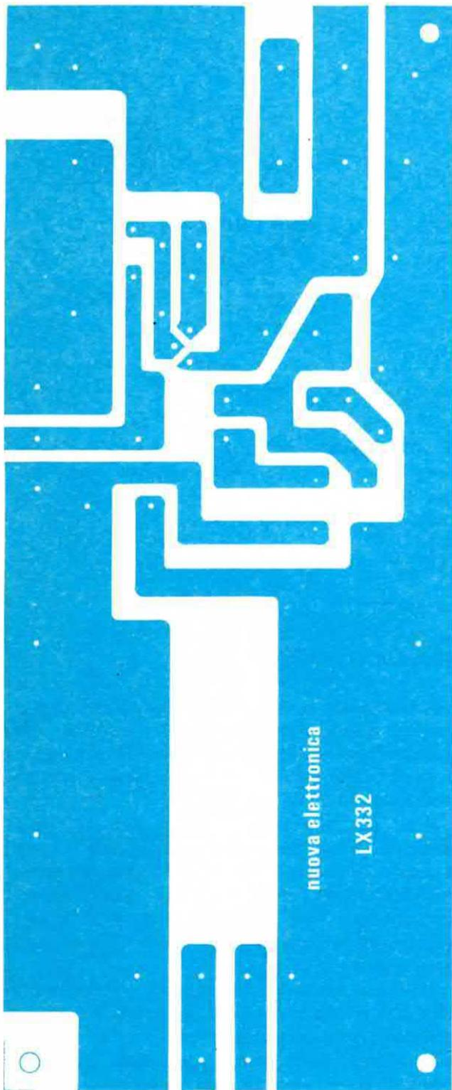
**Fig. 3** Disegno a grandezza naturale del circuito stampato in fibra di vetro necessario per la realizzazione di questo alimentatore stabilizzato.
