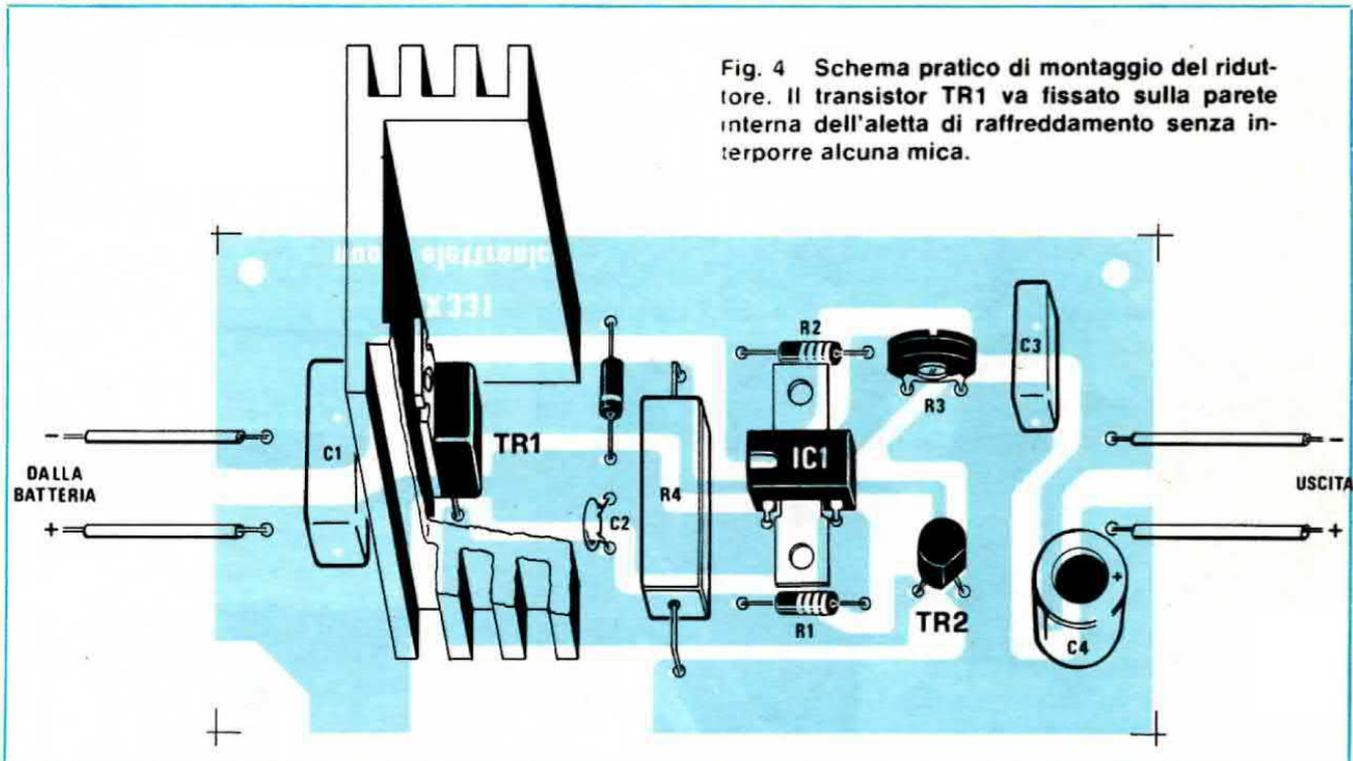
Fig. 4 Schema pratico di montaggio del riduttore. Il transistor TR1 va fissato sulla parete interna dell'aletta di raffreddamento senza interporre alcuna mica.
