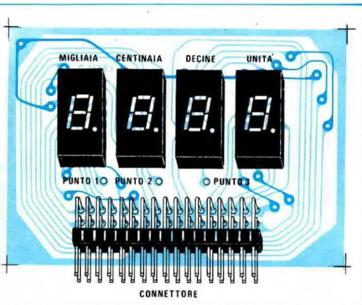
Fig. 10 Schema pratico di montaggio riportato a grandezza naturale del telaio per 4 display. Questo circuito stampato porta la sigla LX.334.D e serve per essere abbinato al telaio qui sotto riportato.
