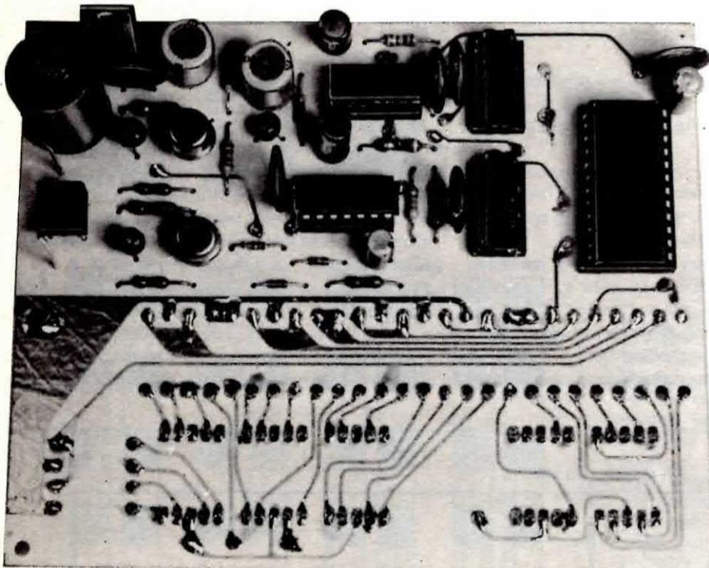
Nella foto, come si presenta il circuito stampato LX336 a montaggio ultimato, visto dal lato componenti. Si noti sulla destra la PROM che costituisce il cuore di tutto il circuito e sulla sinistra lo stadio alimentatore con il ponte e l'integrato stabilizzatore.
