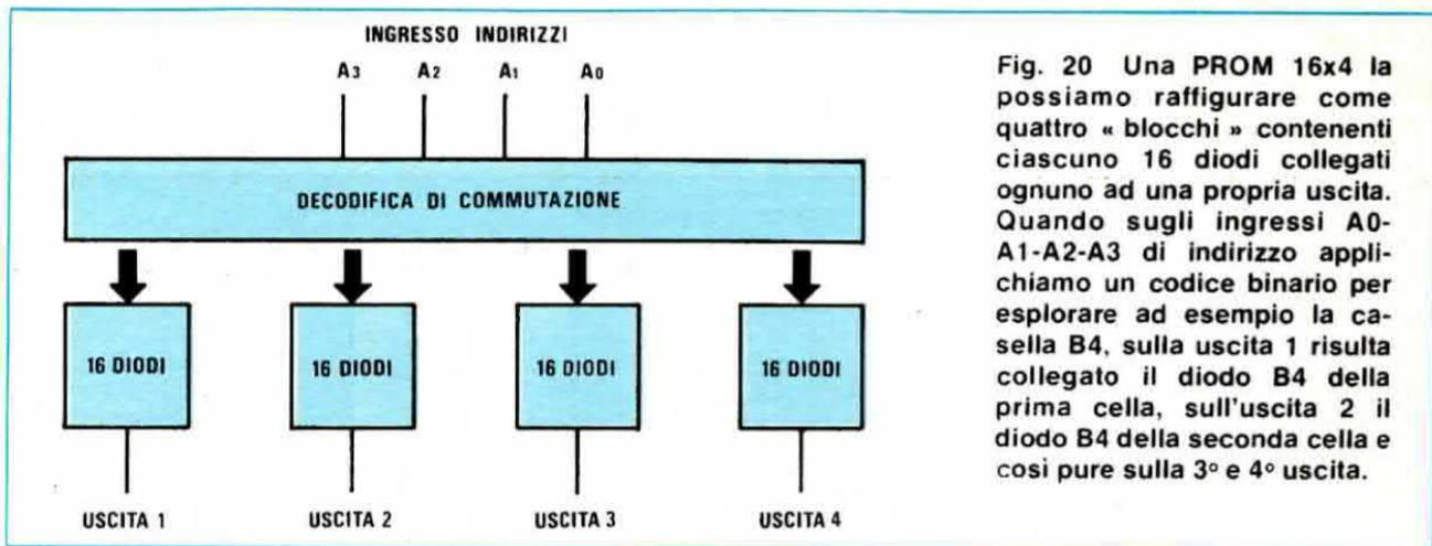
Fig. 20 Una PROM 16x4 la possiamo raffigurare come quattro « blocchi » contenenti ciascuno 16 diodi collegati ognuno ad una propria uscita. Quando sugli ingressi A0-A1-A2-A3 di indirizzo applichiamo un codice binario per esplorare ad esempio la casella B4, sulla uscita 1 risulta collegato il diodo B4 della prima cella, sull'uscita 2 il diodo B4 della seconda cella e così pure sulla 3° e 4° uscita.
