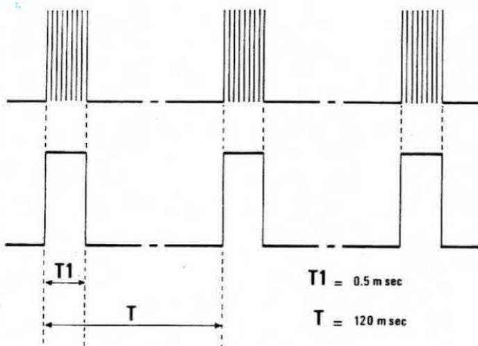
Fig. 3 Quando pigiamo il pulsante P1, i due fotodiodi emettono dei treni d'impulsi alla frequenza di circa 50 KHz intervallati fra di loro di 120 millisecondi.
