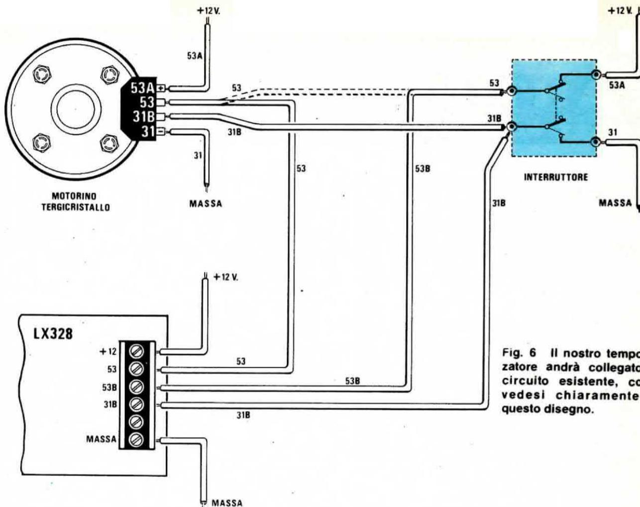
Fig. 6 Il nostro temporizzatore andrà collegato al circuito esistente, come vedesi chiaramente in questo disegno.
