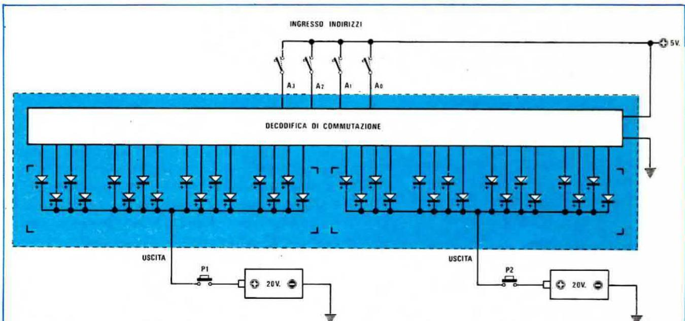
Fig. 18 Poiché all'interno di una PROM 16x2 risultano presenti 16 diodi collegati ad una uscita ed altri 16 collegati ad una seconda uscita, applicando agli ingressi A0-A1-A2-A3 di indirizzo il codice binario relativo per esempio alla cella n. 1, la decodifica di commutazione collegherà sulle due uscite entrambi i diodi contenuti in questa cella, quindi noi possiamo bruciare l'uno o l'altro diodo a seconda di come richiede la nostra tabella di programmazione.
