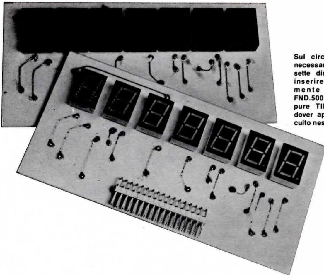
Sul circuito stampato necessario a ricevere i sette display, potremo inserire indifferentemente dei display FND.500 - TIL.322 oppure TIL.322/A senza dover apportare al circuito nessuna modifica.
