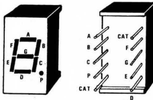
Fig. 2 Connessioni del display LT.303 visto da dietro impiegato per la realizzazione di questi telai.
