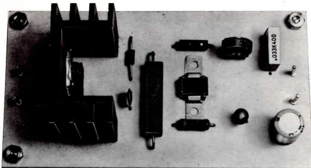
sostituire il darlington TR1 con uno che sia in grado di sopportare fino a 6-8 ampère (per esempio un BDX53) e contemporaneamente ridurre il valore della resistenza R4 portandolo per esempio a 0,18 ohm oppure a 0,12 ohm perché altrimenti, lasciando il valore da noi indicato, la protezione interverrà non appena si superano i 2 ampère.
