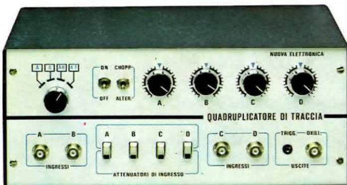
**MOBILE PER 4 TRACCIE OSCILLOSCOPIO**
