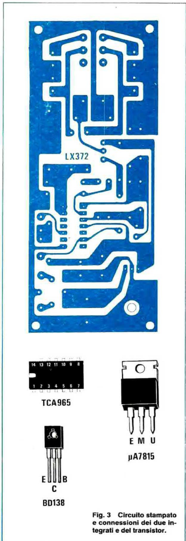
Fig. 3 Circuito stampato e connessioni dei due integrati e del transistor.
