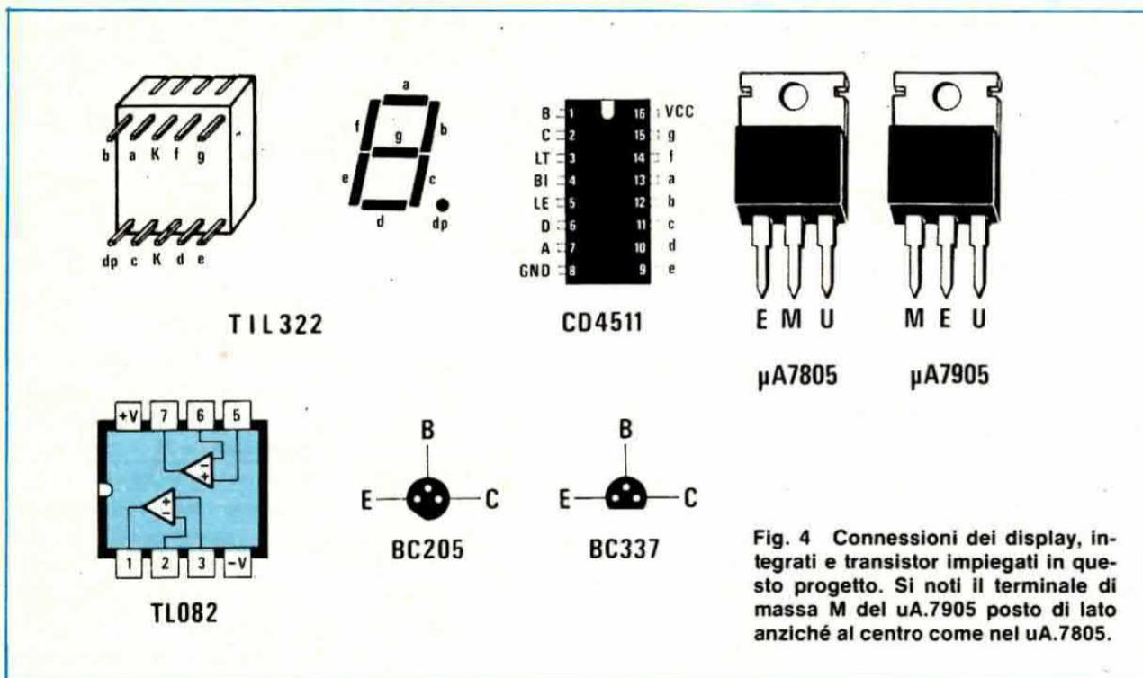
Fig. 4 Connessioni dei display, integrati e transistor impiegati in questo progetto. Si noti il terminale di massa M del uA.7905 posto di lato anziché al centro come nel uA.7805.
