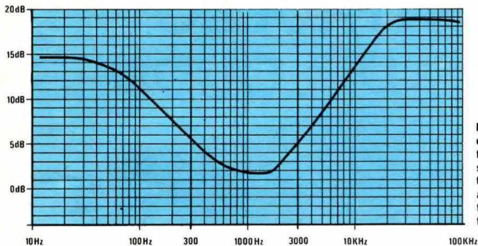
Fig. 1 Come vedesi nel disegno il nostro circuito fra i 300 e i 3.000 Hz presenta un guadagno del tutto trascurabile, mentre amplifica notevolmente tutte le frequenze al di fuori di tale gamma.
