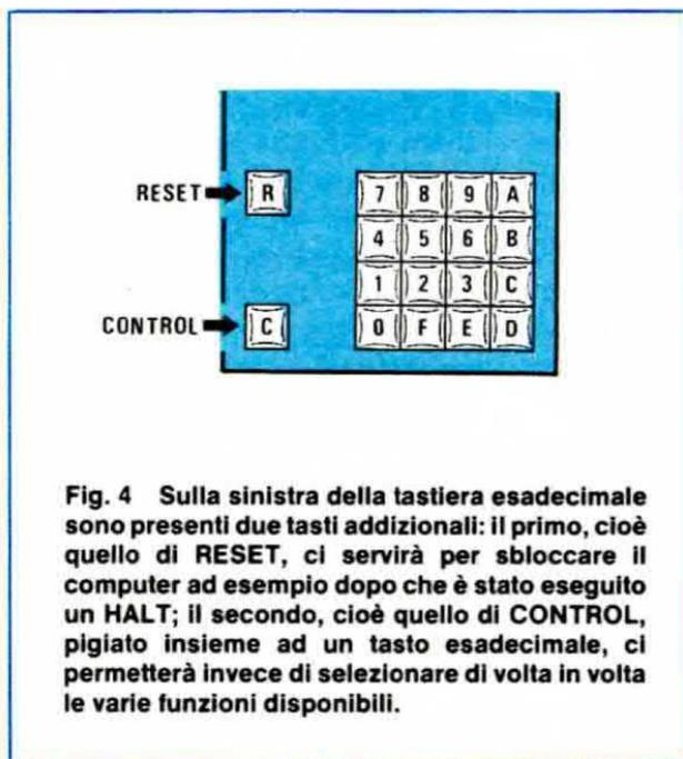
Fig. 4 Sulla sinistra della tastiera esadecimale sono presenti due tasti aggiuntivi: il primo, cioè quello di RESET, ci servirà per sbloccare il computer ad esempio dopo che è stato eseguito un HALT; il secondo, cioè quello di CONTROL, pigiato insieme ad un tasto esadecimale, ci permetterà invece di selezionare di volta in volta le varie funzioni disponibili.
