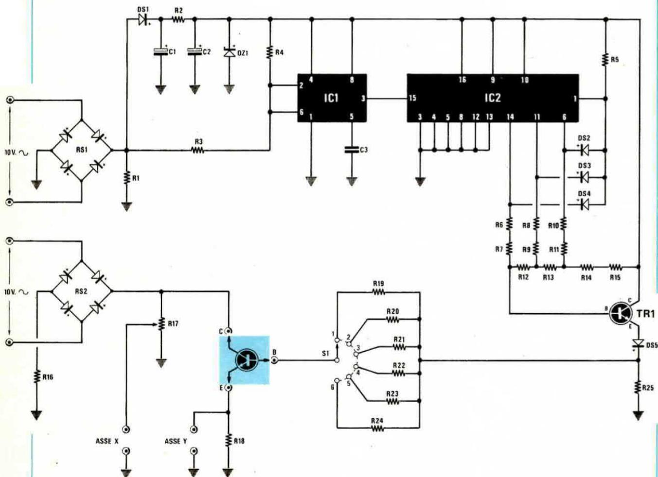
Fig. 1 Schema elettrico del nostro tracciacurve economico. È importante far presente al lettore che ai due ponti raddrizzatori RS1 e RS2 vanno applicate due distinte tensioni di 10 volt, cioè non si pensi di usare un trasformatore da 20 volt con presa centrale, bensì un trasformatore con due avvolgimenti secondari da 10 volt 0,5-1 ampere ciascuno.
