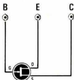
Fig. 14 Collegando un fet come indicato in disegno, potremo far apparire sullo schermo dell'oscilloscopio le sue curve caratteristiche, come visibili sulla foto di destra.
