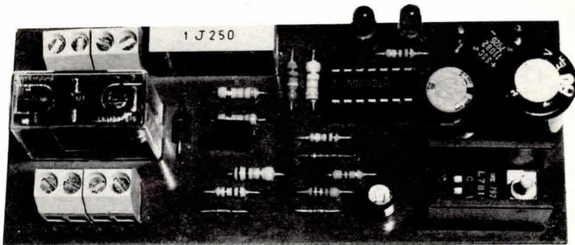
**Foto del montaggio come si presenta a realizzazione ultimata; si noti in basso a destra l'aletta di raffreddamento a U su cui risulta fissato l'integrato stabilizzatore IC2. Per i collegamenti con l'amplificatore e le casse acustiche vedi schema pratico di fig. 2. Fate attenzione, nell'effettuare questi collegamenti, a non scambiare il filo di massa con quello relativo al segnale vero e proprio diversamente potreste creare dei cortocircuiti.**
