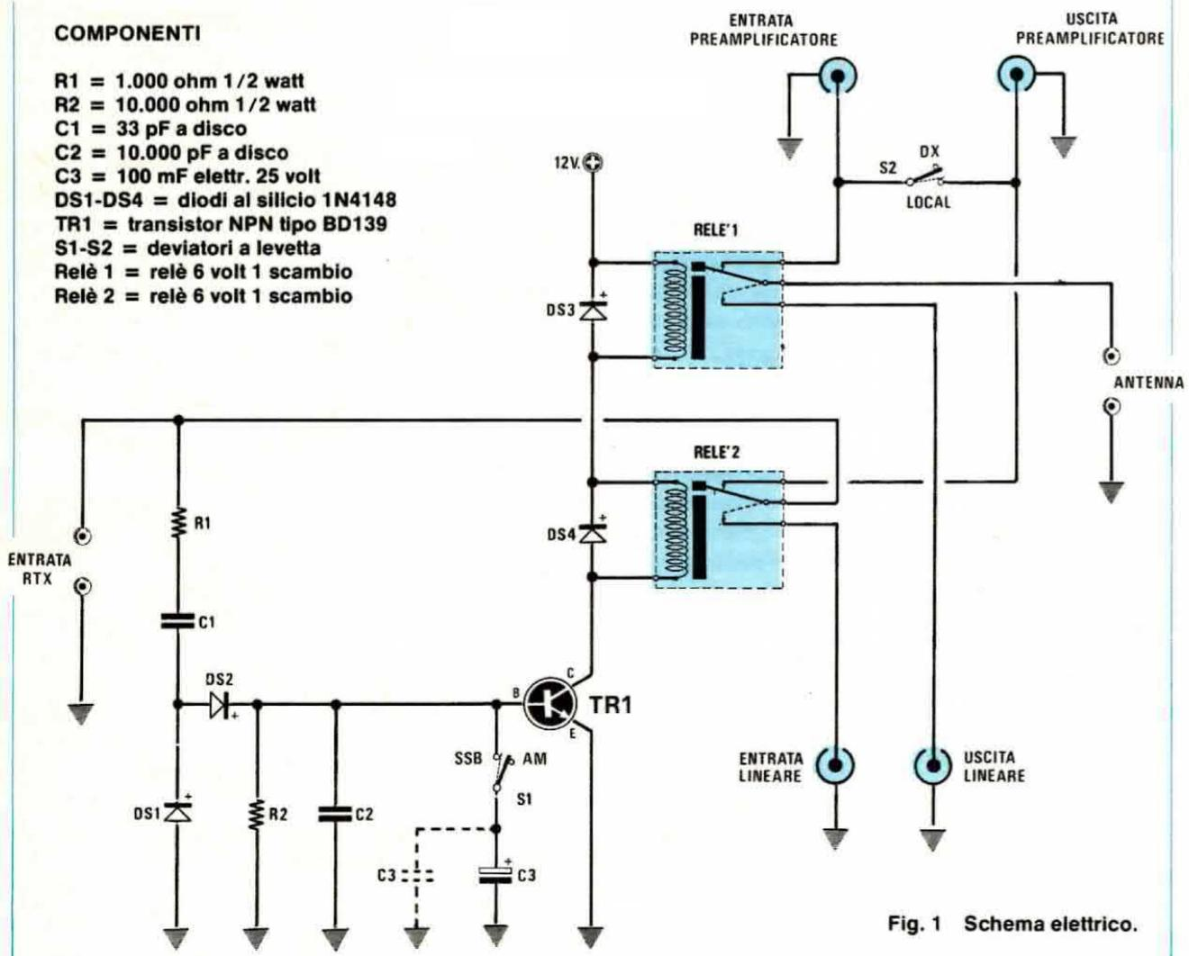
Fig. 1 Schema elettrico.
