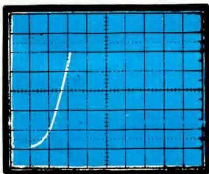
Fig. 12/A Un diodo al germanio provato al tracciacurve presenta una curva simile a quella qui sopra riportata. Si noti l'arrotondamento sul primo quadretto di divisione.
