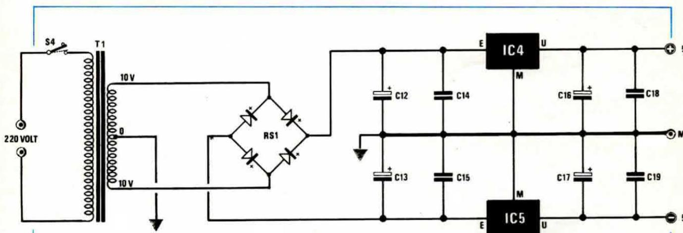
Fig. 3 Schema elettrico dell'alimentatore presente sul circuito stampato dell'ohmetro.
