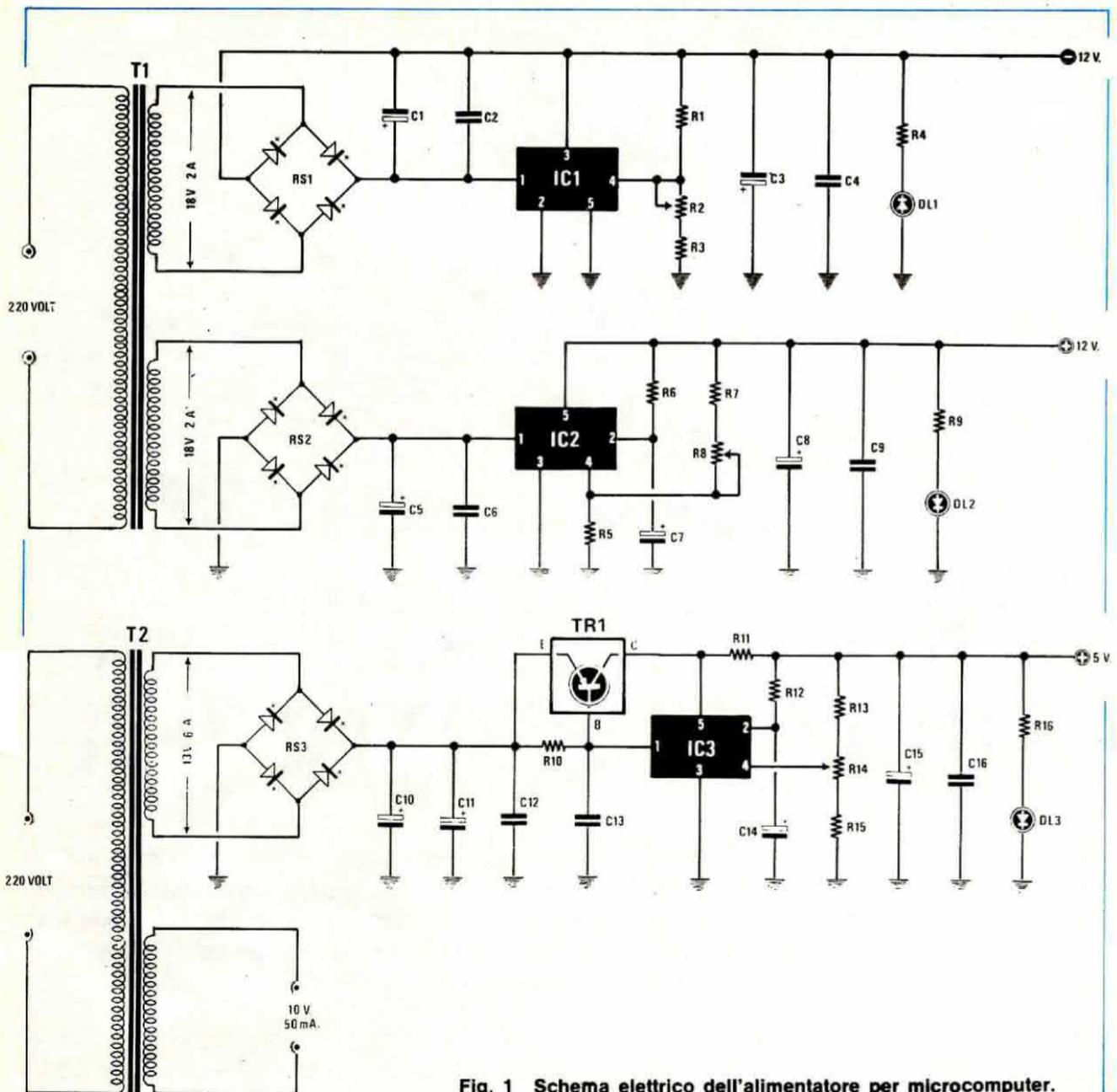
Fig. 1 Schema elettrico dell'alimentatore per microcomputer.
