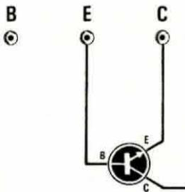
Fig. 10 Per misurare la VEB collegheremo il transistor alle boccole E C come qui sopra indicato. Ogni quadretto in orizzontale della curva che apparirà corrisponderà ad una tensione di 1 volt.
