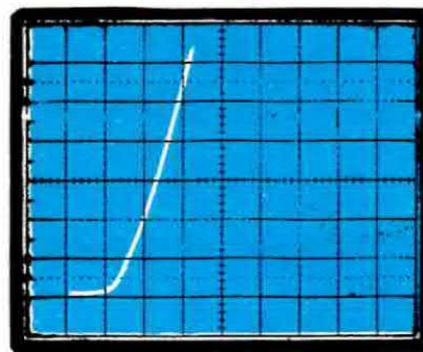
Fig. 12/B Un diodo al silicio si distinguerà da uno al germanio in quanto la sua curva, prima di salire in verticale, risulta per circa un quadretto perfettamente orizzontale.
