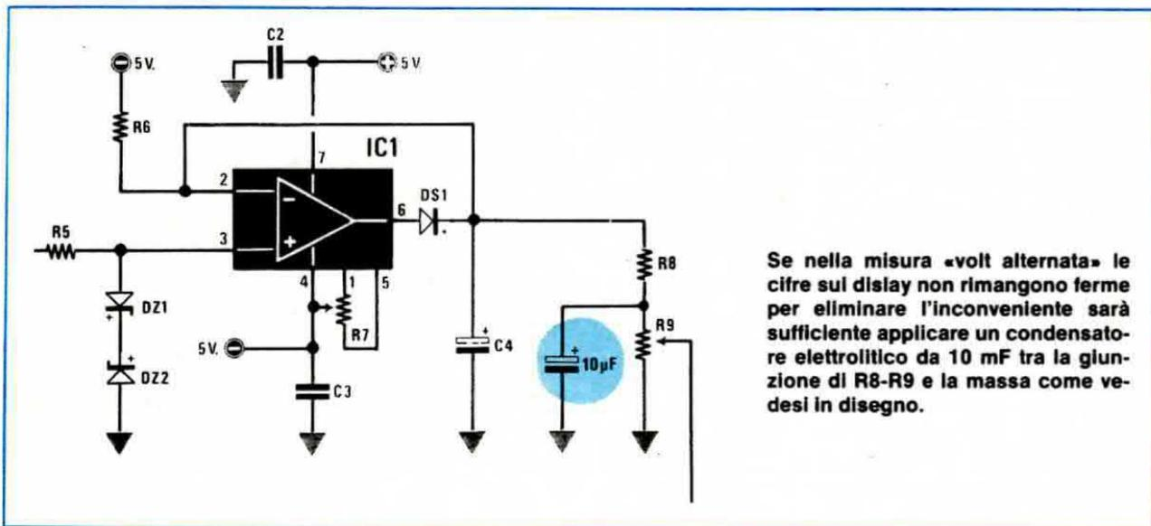
Se nella misura « volt alternata » le cifre sul display non rimangono ferme per eliminare l'inconveniente sarà sufficiente applicare un condensatore elettrolitico da 10 mF tra la giunzione di R8-R9 e la massa come vedesi in disegno.
