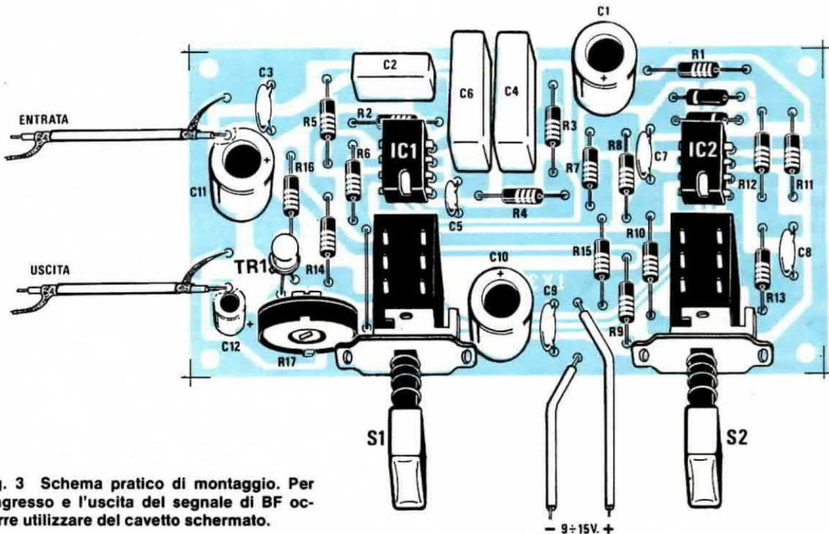
Fig. 3 Schema pratico di montaggio. Per l'ingresso e l'uscita del segnale di BF occorre utilizzare del cavetto schermato.
