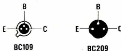
Fig. 5 Connessioni del transistor BC109 e del suo equivalente BC209 visti entrambi dal lato in cui fuoriescono i terminali, cioè dal di sotto.
