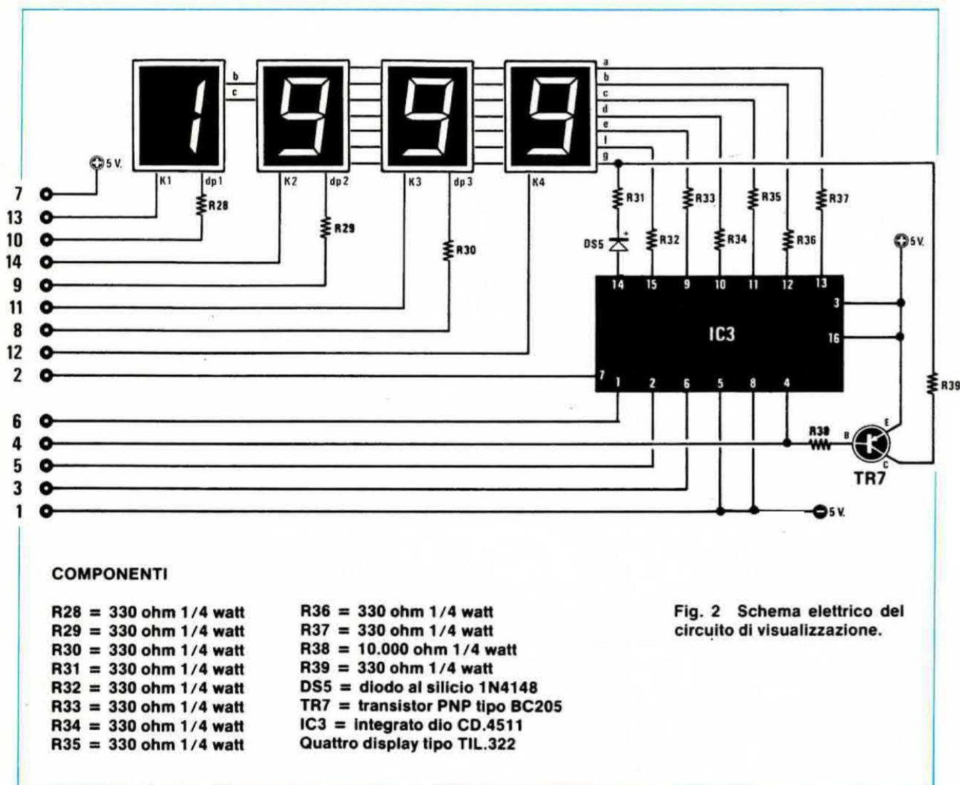
Fig. 2 Schema elettrico del circuito di visualizzazione.
