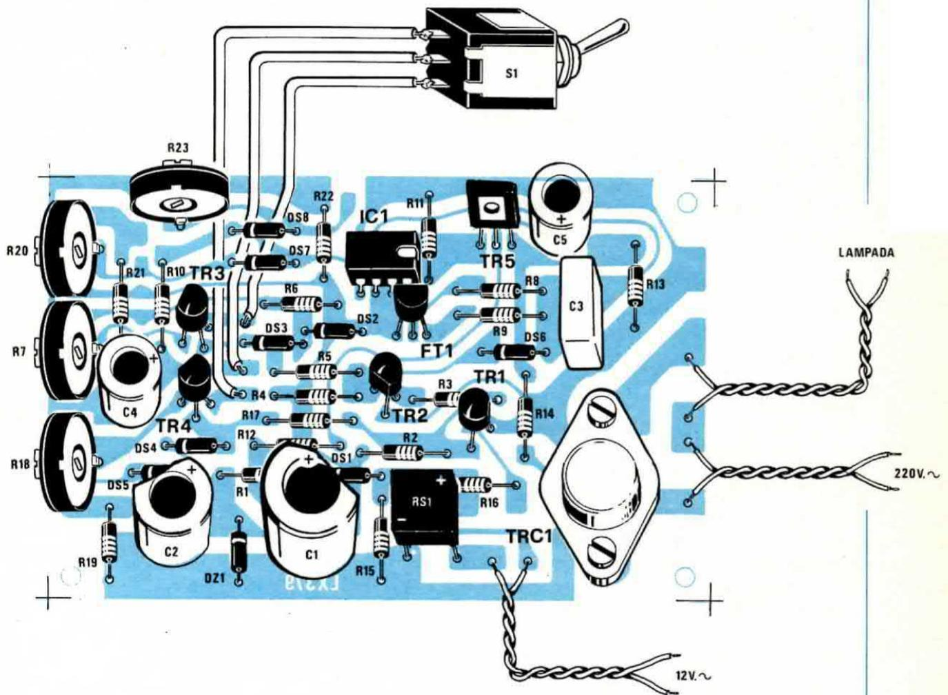
**Fig. 6** Schema pratico di montaggio. Si fa presente al lettore che tutti i componenti, comprese le piste del circuito stampato, sono in contatto diretto con la tensione di rete dei 220 volt, quindi il circuito va racchiuso entro un mobile, isolandolo se questo è di metallo, per non ricevere la scossa quando lo si tocca.
