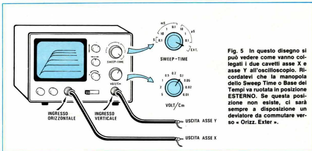
Fig. 5 In questo disegno si può vedere come vanno collegati i due cavetti asse X e asse Y all'oscilloscopio. Ricordatevi che la manopola dello Sweep Time o Base dei Tempi va ruotata in posizione ESTERNO. Se questa posizione non esiste, ci sarà sempre a disposizione un deviatore da commutare verso « Orizz. Exter ».
