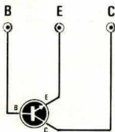
Fig. 6 Per provare l'efficienza di un transistor NPN lo collegheremo come vedesi in disegno. Agendo sul commutatore S1 della corrente di base riusciremo quindi a far apparire sullo schermo questa figura.
