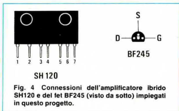
Fig. 4 Connessioni dell'amplificatore ibrido SH120 e del fet BF245 (visto da sotto) impiegati in questo progetto.
