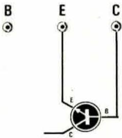
Fig. 9 Per misurare la VBE il transistor andrà collegato al nostro tracciacurve come qui indicato; così facendo si otterrà sullo schermo una traccia simile a quella riportata qui a destra.
