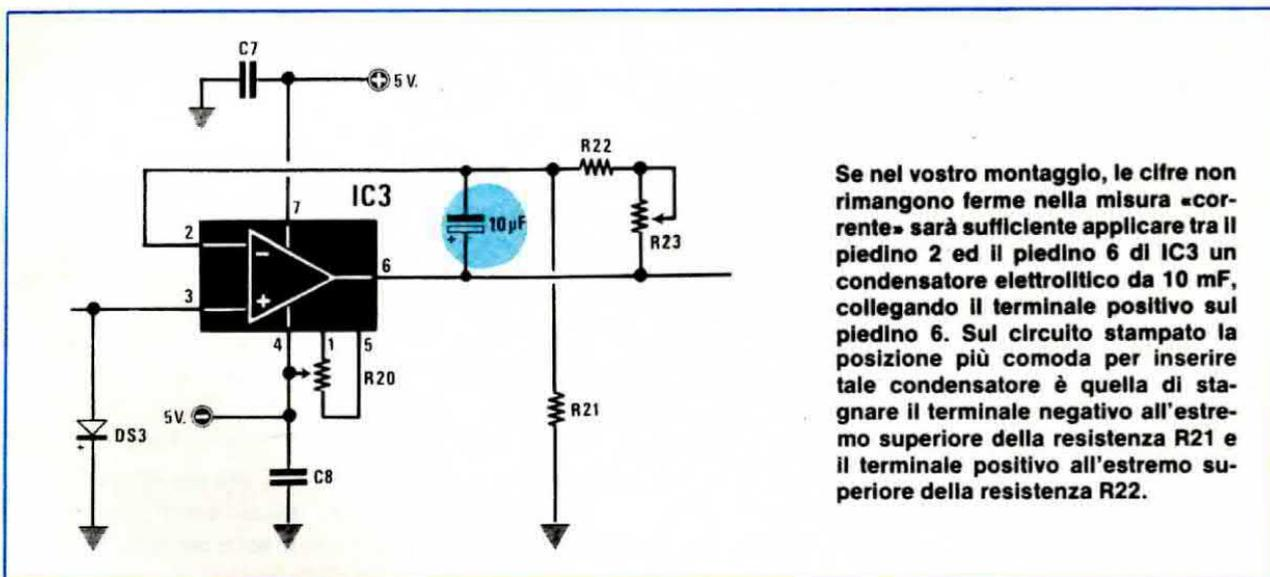
Se nel vostro montaggio, le cifre non rimangono ferme nella misura «corrente» sarà sufficiente applicare tra il piedino 2 ed il piedino 6 di IC3 un condensatore elettrolitico da 10 mF, collegando il terminale positivo sul piedino 6. Sul circuito stampato la posizione più comoda per inserire tale condensatore è quella di stagnare il terminale negativo all'estremo superiore della resistenza R21 e il terminale positivo all'estremo superiore della resistenza R22.
