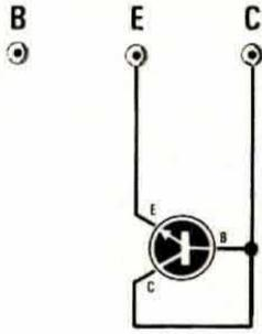
Fig. 8 Per misurare la VCE di saturazione di un transistor dovremo collegarlo come vedesi in figura; la curva che otterremo sarà similare a quella visibile qui sulla destra.
