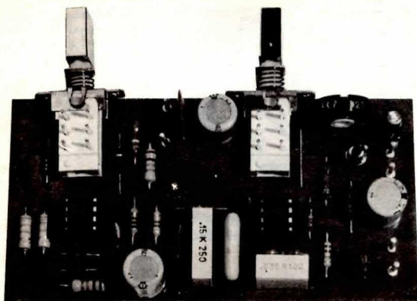
Foto del preamplificatore distortore. Si notino i due commutatori a tastiera richiesti per far funzionare il circuito come semplice preamplificatore, oppure come semplice distortore o distortore duplicatore.
