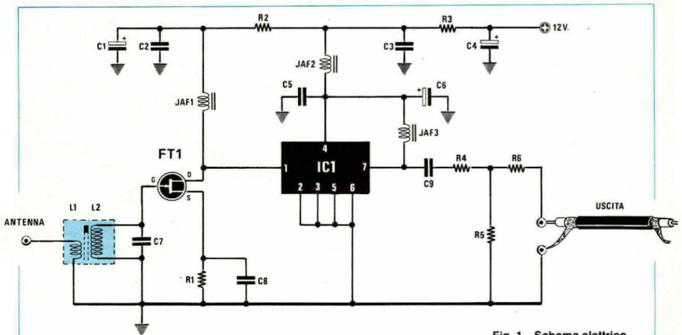
Fig. 1 Schema elettrico.
