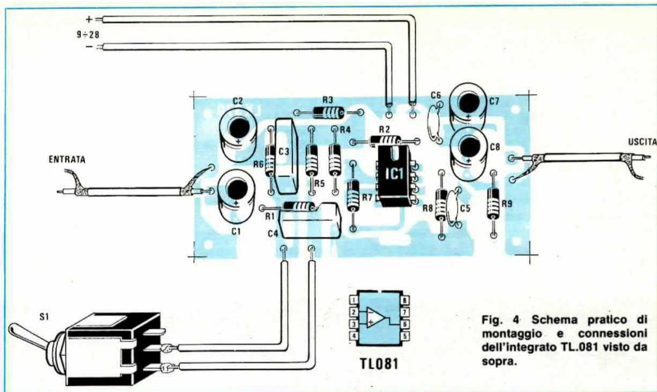
Fig. 4 Schema pratico di montaggio e connessioni dell'integrato TL081 visto da sopra.
