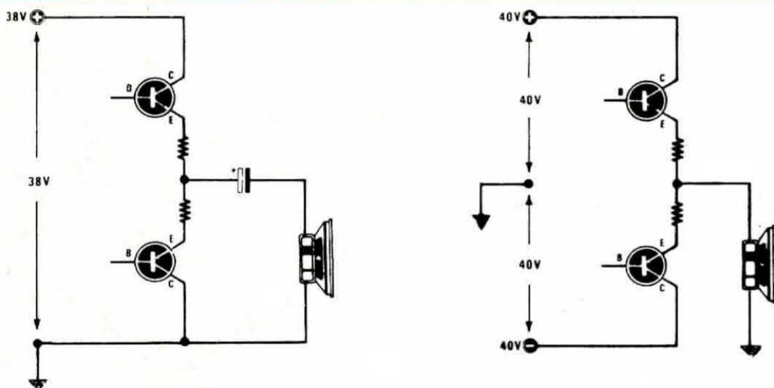
**Fig. 4** La protezione per casse serve solo ed unicamente per quegli amplificatori che funzionano con tensione duale (vedi disegno sulla destra), cioè non dispongono di un condensatore di disaccoppiamento fra l'uscita e l'altoparlante. Se tale condensatore è presente (vedi disegno a sinistra) la protezione non è più necessaria in quanto la corrente continua non potrà mai raggiungere le casse quindi anche se salta un transistor finale sull'amplificatore le casse non corrono alcun pericolo.
