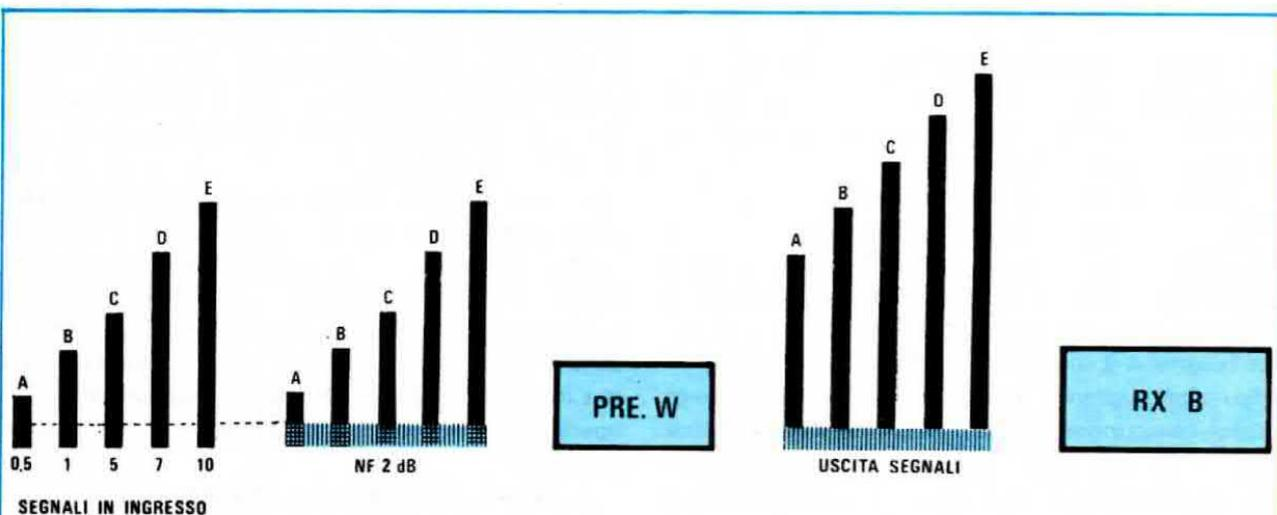
Fig. 7 Se abbiamo un ricevitore RXB con una cifra di rumore di 10 dB, quindi così poco sensibile da ricevere solo l'emittente la cui ampiezza è tale da superare la soglia di rumore, applicandogli in ingresso il preamplificatore W che ha una cifra di rumore bassissima (solo 2 dB) otterremo un ricevitore professionale in grado di farci ascoltare qualsiasi segnale raggiunta la nostra antenna.
