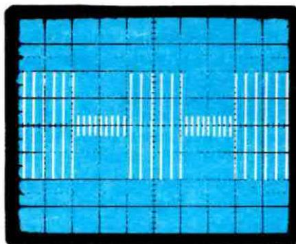
Fig. 15 Se come vedesi in questa foto la frequenza dei 2400 Hz risultasse troppo attenuata rispetto ai 1200 Hz, il micro-computer indicherà « errore » e fermerà il motorino del registratore (leggere note articolo).
