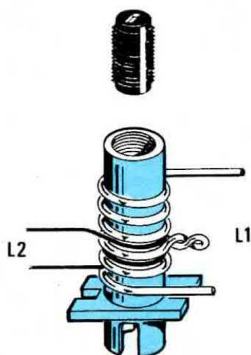
Fig. 3 Bobina di sintonia L1/L2
