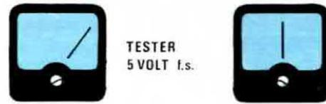
Fig. 9 Se tareremo la scheda con il tester sui terminali TP1 rileveremo inizialmente una tensione positiva che può variare da un minimo di 3,5 ad un max di 4,2 volt. Il trimmer da 50.000 ohm andrà ruotato fino ad ottenere in questo punto una « tensione zero ».
