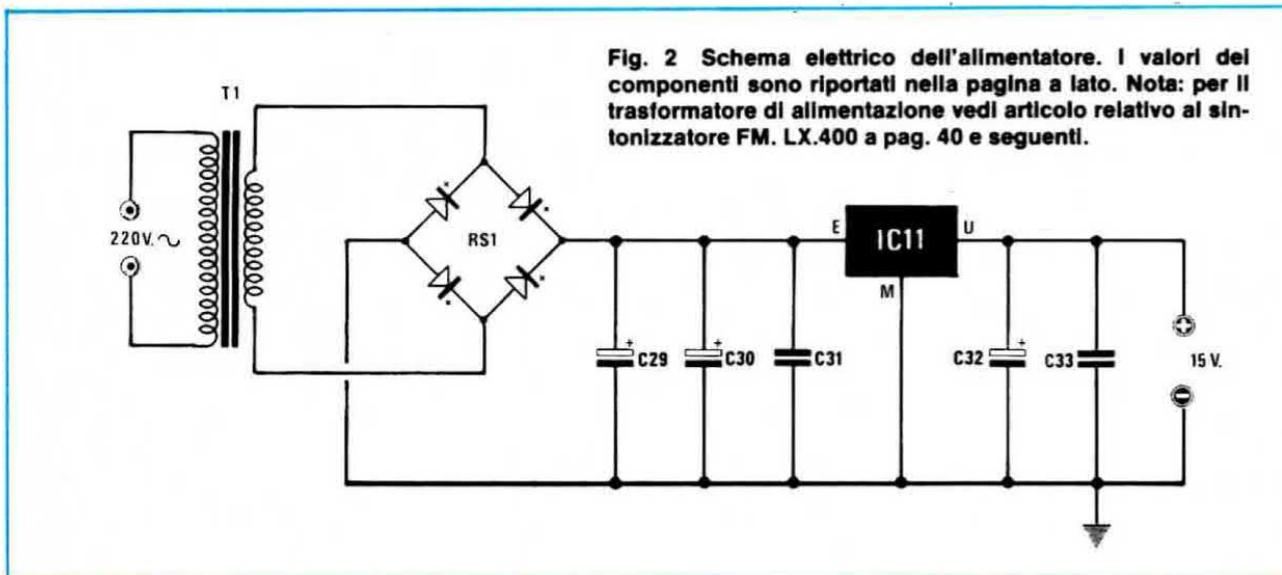
Fig. 2 Schema elettrico dell'alimentatore. I valori dei componenti sono riportati nella pagina a lato. Nota: per il trasformatore di alimentazione vedi articolo relativo al sintonizzatore FM. LX.400 a pag. 40 e seguenti.
