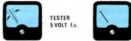
Fig. 10 Quando ci avvicineremo al « punto di taratura » vedremo la lancetta oscillare leggermente intorno allo zero a causa dei piccoli impulsi di fig. 7. Solo quando la lancetta risulterà immobile (vedi a destra) la scheda risulterà perfettamente tarata.
