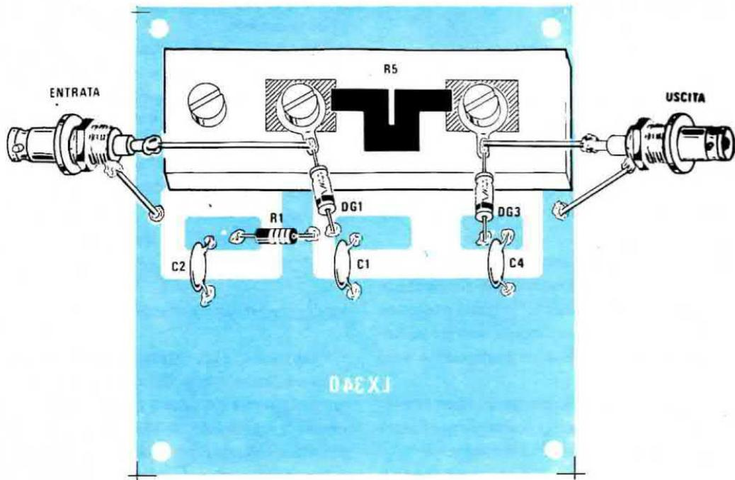
**Fig. 5** Schema pratico di montaggio del ponte AF visto dai due lati del circuito stampato. Si noti la resistenza antiinduttiva da 52 ohm (R5) e i relativi collegamenti con i bocchettoni BNC di entrata e uscita.
