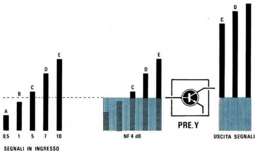
**Fig. 2** A parità di guadagno, un preamplificatore che disponga di una cifra di rumore più bassa (per esempio 4 dB contro i 10 dB di fig. 1) ci permetterà sempre di ottenere maggiori vantaggi infatti anche i segnali più deboli riusciranno a superare la soglia di rumore in ingresso e ad essere quindi amplificati.
