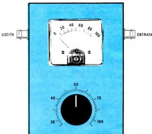
**Fig. 7** Per controllare l'impedenza di un'antenna il ponte dovrà essere collegato tra l'uscita del trasmettitore e il cavo di discesa dell'antenna stessa. A questo punto accenderemo il trasmettitore e ruoteremo la manopola fino a portare la lancetta dello strumento sullo « zero » dopodiché leggeremo il valore di impedenza sulla scala graduata.
