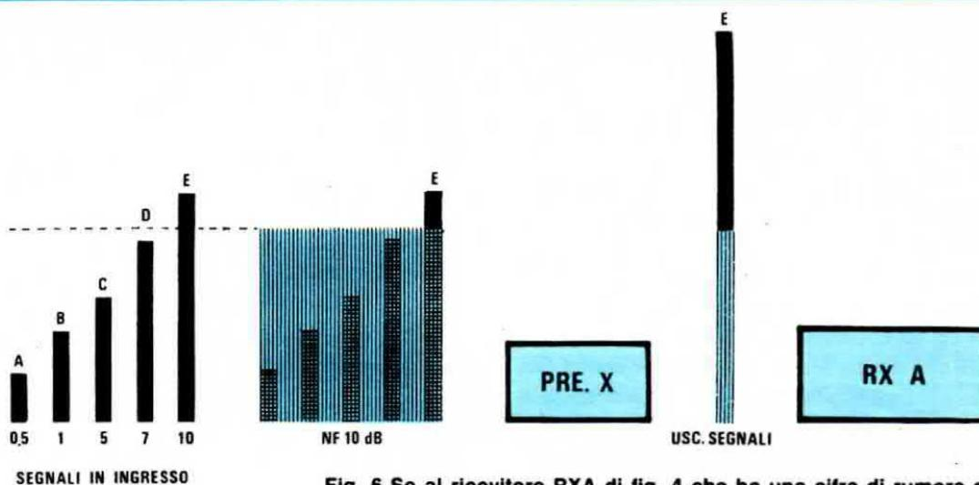
Fig. 6 Se al ricevitore RXA di fig. 4 che ha una cifra di rumore di 4 dB, applichiamo in ingresso il preamplificatore X che ha una cifra di rumore di 10 dB, anche se questo amplifica il segnale di 100 volte non faremo altro che peggiorare la situazione, infatti il ricevitore da solo riusciva a captare le emittenti C-D-E, mentre inserendo il preamplificatore riuscirà a captare solo l'emittente E.
