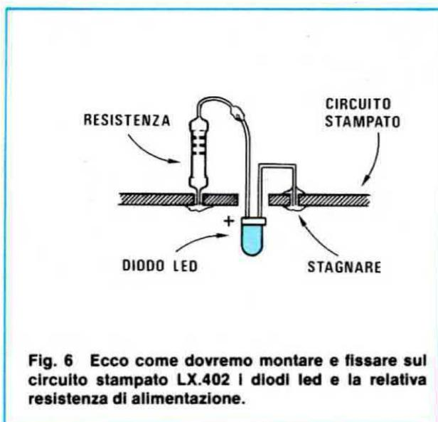
**Fig. 6** Ecco come dovremo montare e fissare sul circuito stampato LX.402 i diodi led e la relativa resistenza di alimentazione.
