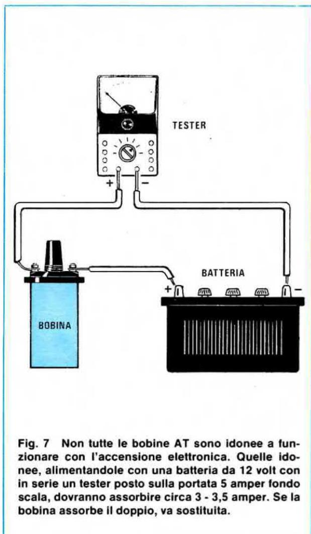
**Fig. 7** Non tutte le bobine AT sono idonee a funzionare con l'accensione elettronica. Quelle idonee, alimentandole con una batteria da 12 volt con in serie un tester posto sulla portata 5 amper fondo scala, dovranno assorbire circa 3 - 3,5 amper. Se la bobina assorbe il doppio, va sostituita.
