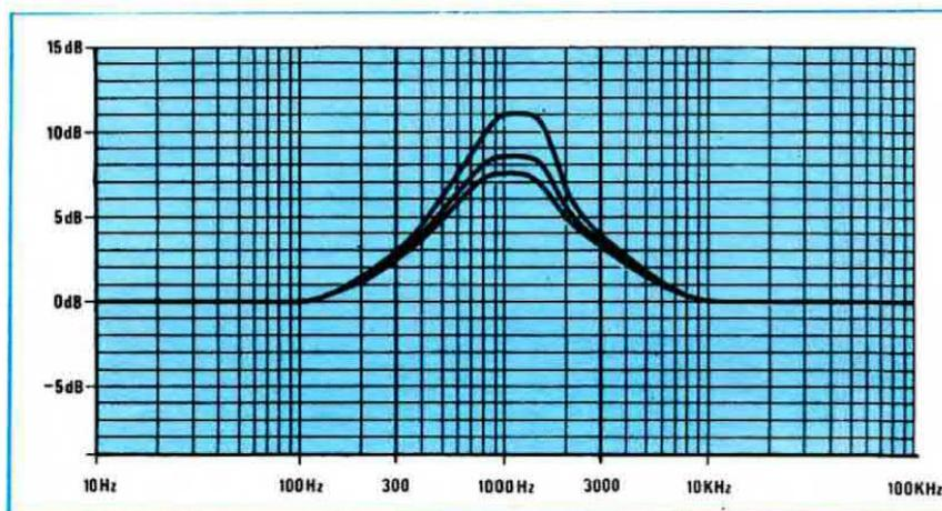
**Fig. 2** In questo grafico è possibile vedere come risultano amplificati in uscita dal filtro i segnali di frequenza compresa fra 300 e 3.000 Hz rispettivamente impiegando per R5 una resistenza da 100 ohm, 33.000 ohm e 56.000 ohm. La curva più in alto si riferisce ovviamente ai 100 ohm.
