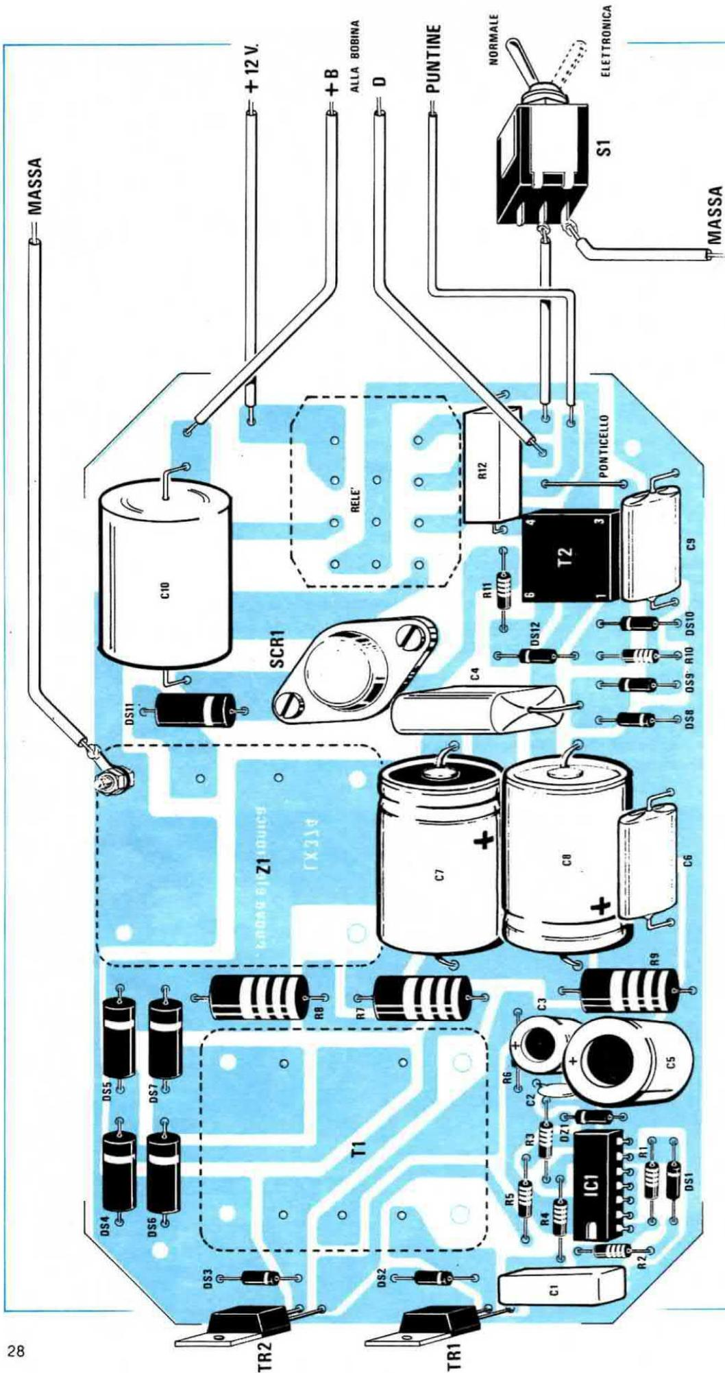
Fig. 2 Schema pratico di montaggio. Si raccomanda di rispettare la numerazione dei piedini del trasformatore d'innesto T2 e di effettuare il ponticello con filo di rame sui due fori posti davanti sempre a T2. I terminali + B e D vanno collegati alla bobina AT.
