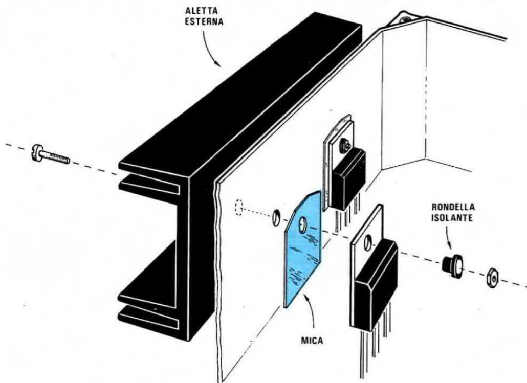
**Fig. 6** I due transistor darlington TR1 - TR2 andranno fissati sul contenitore metallico non dimenticando di interporre una mica e di isolare la vite di fissaggio con l'apposita rondella di plastica. All'esterno dovrete fissare l'aletta di raffreddamento che troverete nel kit.
