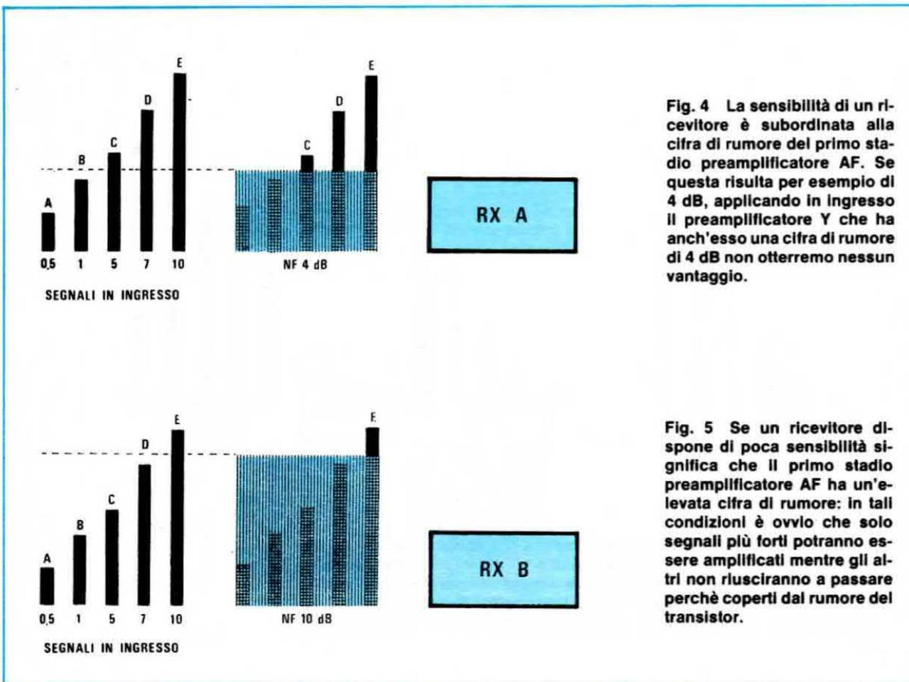
Fig. 4 La sensibilità di un ricevitore è subordinata alla cifra di rumore del primo stadio preamplificatore AF. Se questa risulta per esempio di 4 dB, applicando in ingresso il preamplificatore Y che ha anch'esso una cifra di rumore di 4 dB non otterremo nessun vantaggio.
