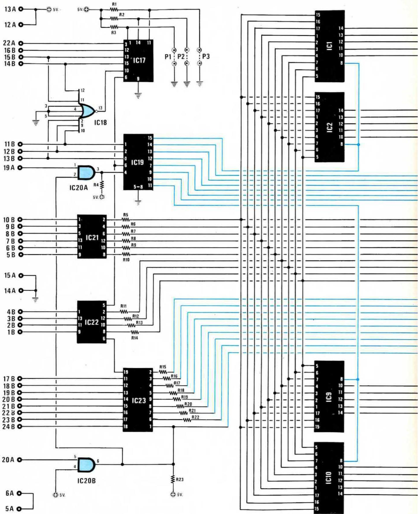
Fig. 1 Schema elettrico espansione memoria da 8 K.
