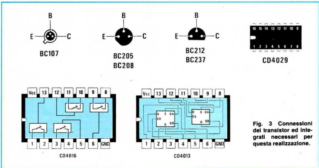
Fig. 3 Connessioni dei transistor ed integrati necessari per questa realizzazione.
