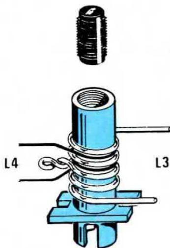
Fig. 4 Bobina oscillatrice L3/L4
