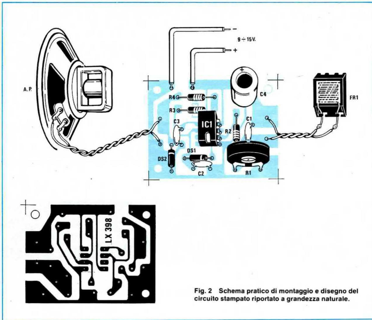
Fig. 2 Schema pratico di montaggio e disegno del circuito stampato riportato a grandezza naturale.
