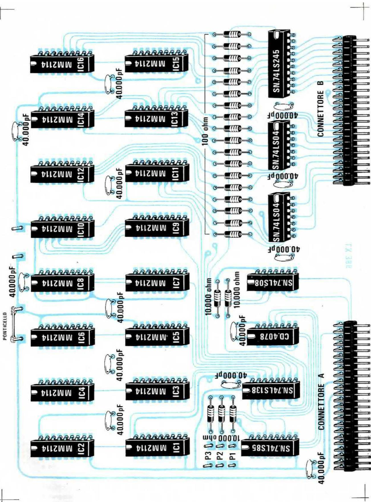
Fig. 2 Schema pratico dell'espansione di memoria. Nota ricordarsi di fare il « ponticello » su due terminali indicati in alto; gli altri due terminali vanno lasciati aperti. Per i terminali P1 - P2 - P3 leggere attentamente l'articolo. I condensatori da 40.000 pF o 47.000 pF sono tutti condensatori di « filtro » collegati sulla rete di alimentazione a 5 volt.
