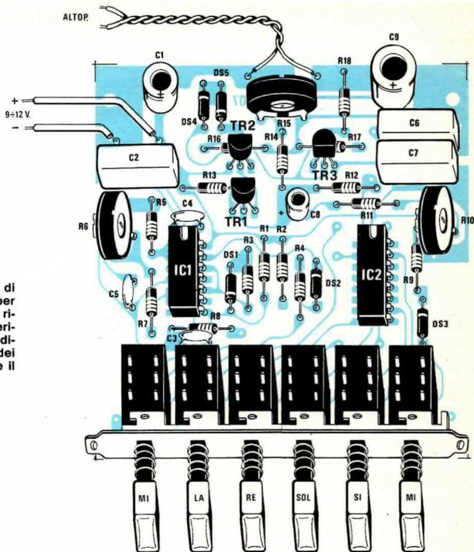
Fig. 3 Schema pratico di montaggio del corista per chitarra. Nel montaggio rispettare la tacca di riferimento degli integrati e la disposizione dei terminali dei transistor per non invertire il terminale E con quello C.
