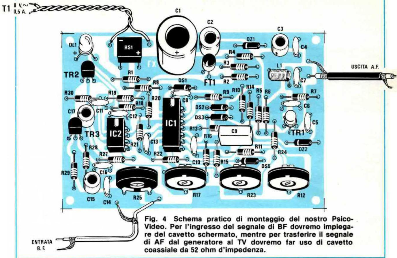
**Fig. 4** Schema pratico di montaggio del nostro Psico-Video. Per l'ingresso del segnale di BF dovremo impiegare del cavetto schermato, mentre per trasferire il segnale di AF dal generatore al TV dovremo far uso di cavetto coassiale da 52 ohm d'impedenza.
