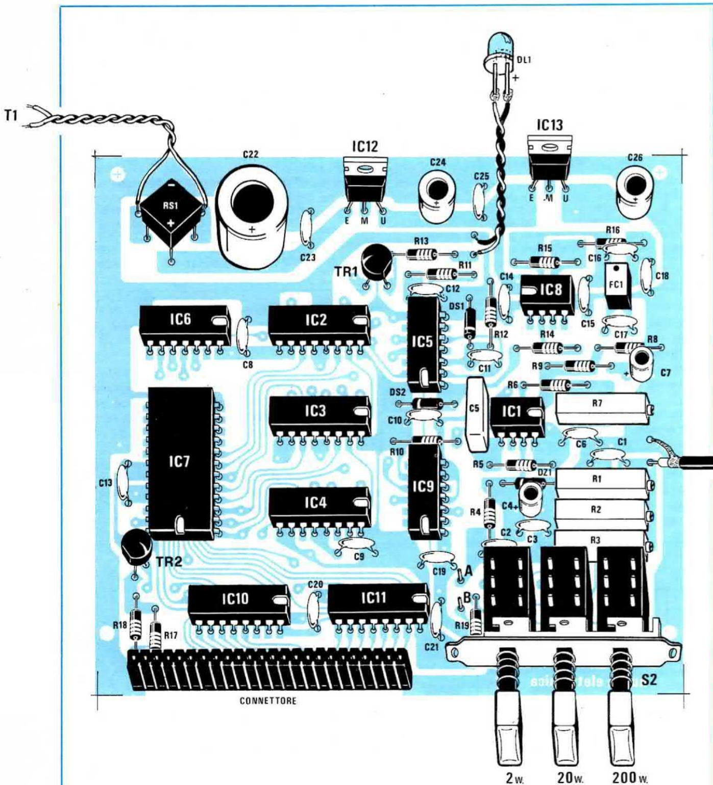
Fig. 8 Schema pratico di montaggio del wattmetro di AF esclusa la sonda di carico che come vedesi in fig. 12 andrà fissata sull'aletta laterale del mobile.
