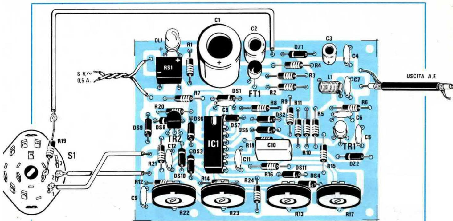
**Fig. 5** Schema pratico per la realizzazione del nostro generatore di reticolo. Per evitare distorsioni sull'immagine si consiglia di montare il circuito dentro una scatola metallica e di tenere distanziati tra loro i fili che dal circuito stampato vanno a collegarsi ai terminali del commutatore rotativo S1. Nota. Il corpo metallico del commutatore S1 andrà collegato a massa, condizione questa che otterremo automaticamente chiudendo il tutto entro una scatola metallica.
