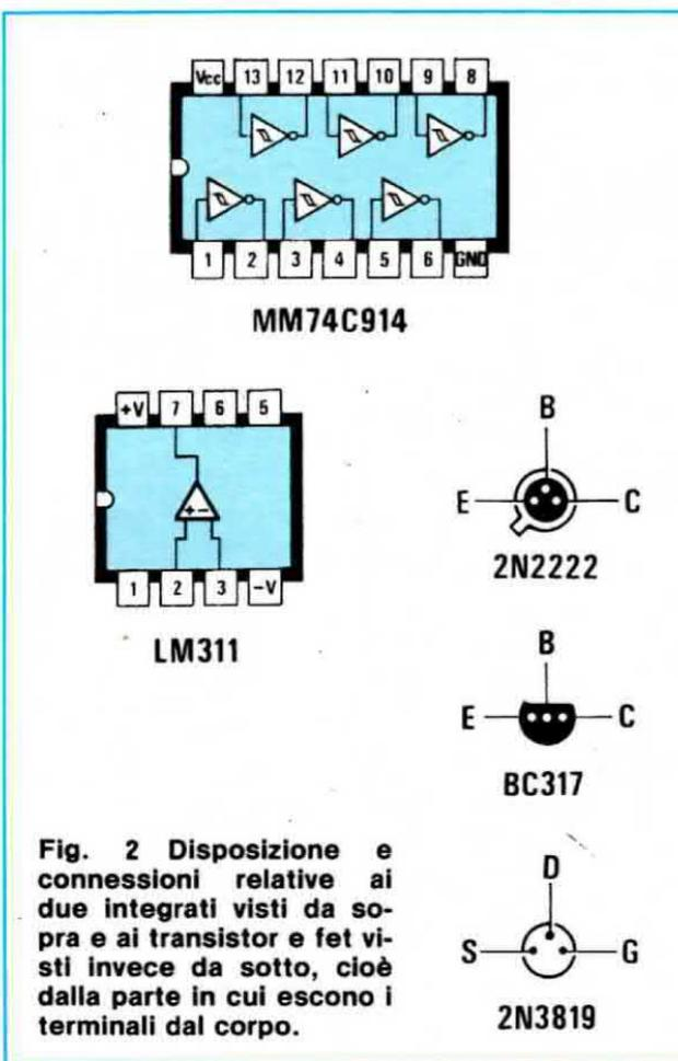
Fig. 2 Disposizione e connessioni relative ai due integrati visti da sopra e ai transistor e fet visti invece da sotto, cioè dalla parte in cui escono i terminali dal corpo.
