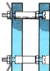
**Fig. 13** Per realizzare la sonda da 200 watt, le resistenze poste in parallelo fra di loro dovranno risultare distanziate di circa 1 cm tramite dei distanziatori di alluminio. Controllate con un ohmetro che i terminali delle due resistenze poste in parallelo risultino perfettamente in contatto tra di loro, cioè si ottenga una resistenza totale di 25-26 ohm.
