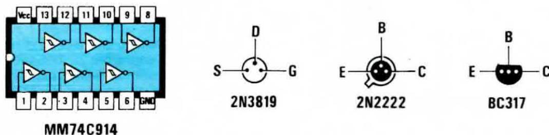
**Fig. 2** Connessioni dell'integrato 74C.914 visto da sopra e dei transistor e fet visti invece da sotto. Per il fet impiegate un 2N3819 con involucro circolare perché quelli con involucro a mezzaluna presentano i terminali disposti in modo diverso.
