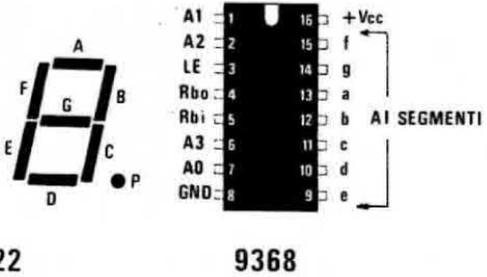
Fig. 9 Connessioni degli integrati, del transistor, del filtro ceramico e del display utilizzati per la realizzazione di questo progetto.
