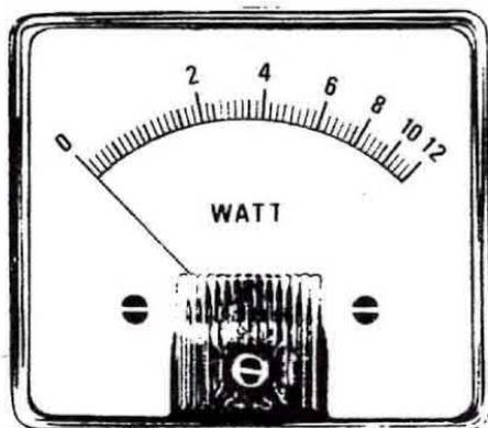
**Fig. 1** Nei wattmetri analogici che impiegano uno strumento ad indice la scala, come vedesi in figura, non è lineare bensì man mano che ci si avvicina al fondo scala, a parità di salto di potenza, le tacche si avvicinano fra di loro — vedi differenza da 0 a 2 watt e da 10 a 12 watt. Di lato. La tabella delle tensioni di picco necessarie per ottenere diversi valori di potenza.
