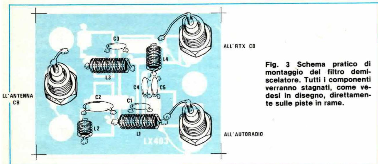
Fig. 3 Schema pratico di montaggio del filtro demiscelatore. Tutti i componenti verranno stagnati, come vedesi in disegno, direttamente sulle piste in rame.
