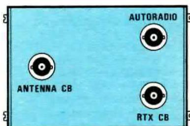
**Fig. 5** Sul pannello della scatola dovremo indicare in prossimità dei bocchettoni BNC, quale dei tre va collegato all'antenna, quale all'autoradio e quale invece all'ingresso del ricetrasmittitore perché se per caso li invertissimo il circuito non funzionerà.
