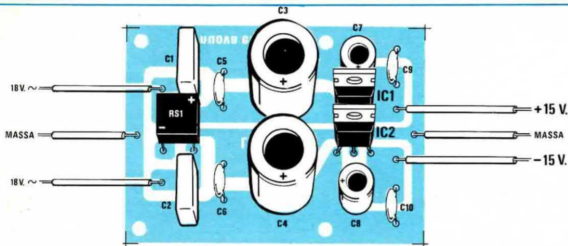
**Fig. 4** Schema pratico di montaggio dell'alimentatore. Questo circuito è particolarmente adatto per tutti quei montaggi elettronici a basso assorbimento che richiedono tensioni duali, anche perché sostituendo i due soli integrati è possibile ricavare in uscita tensioni di valore diverso.
