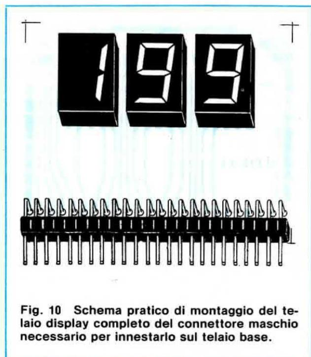
Fig. 10 Schema pratico di montaggio del telaio display completo del connettore maschio necessario per innestarlo sul telaio base.
