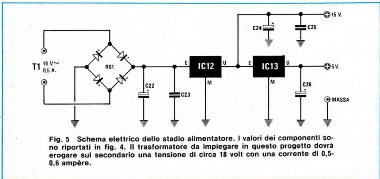
**Fig. 5** Schema elettrico dello stadio alimentatore. I valori dei componenti sono riportati in fig. 4. Il trasformatore da impiegare in questo progetto dovrà erogare sul secondario una tensione di circa 18 volt con una corrente di 0,5-0,6 ampère.
