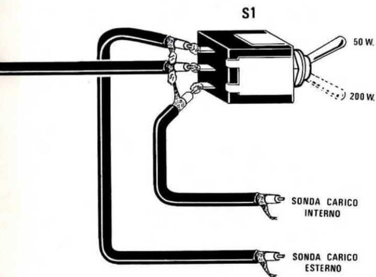
Per collegare al nostro wattmetro la sonda interna da 50 watt oppure quella esterna da 200 watt, utilizzeremo un deviatore a levetta. Si raccomanda di effettuare questi collegamenti con cavo coassiale da 52 ohm non dimenticandosi di stagnare insieme le tre calze metalliche.
