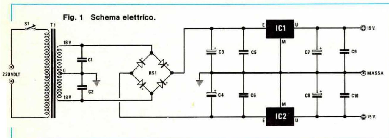
pre una tensione di alimentazione duale e poiché difficilmente si dispone in laboratorio di un simile alimentatore, si è sempre costretti, in questi casi, ad effettuare noiosissimi collegamenti volanti fra due alimentatori a tensione singola oppure fra due gruppi di pile per poter raggiungere lo scopo.
