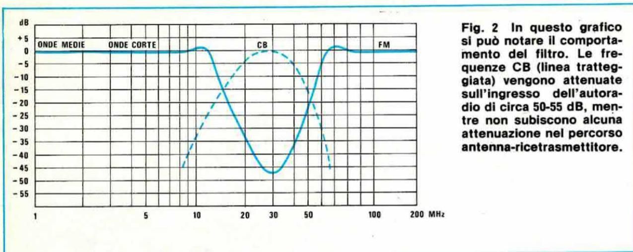
Fig. 2 In questo grafico si può notare il comportamento del filtro. Le frequenze CB (linea tratteggiata) vengono attenuate sull'ingresso dell'autoradio di circa 50-55 dB, mentre non subiscono alcuna attenuazione nel percorso antenna-ricetrasmittitore.
