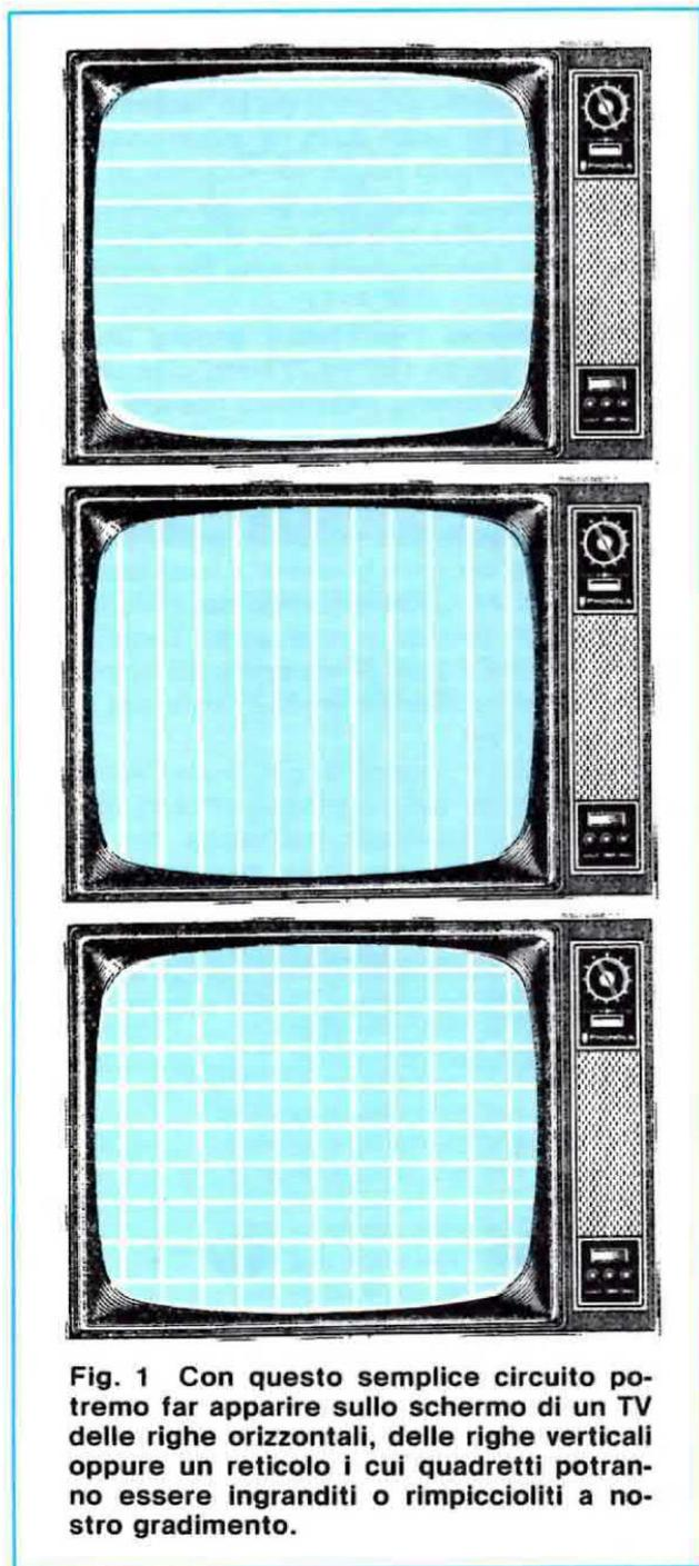
**Fig. 1** Con questo semplice circuito potremo far apparire sullo schermo di un TV delle righe orizzontali, delle righe verticali oppure un reticolo i cui quadretti potranno essere ingranditi o rimpiccioliti a nostro gradimento.
