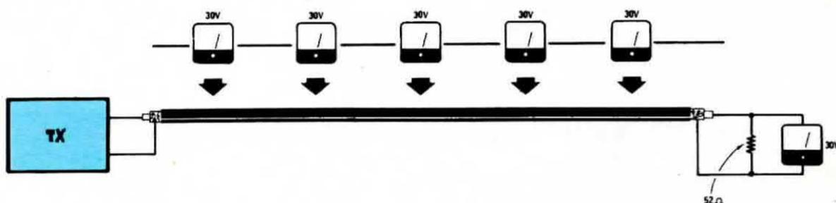
**Fig. 16** Se l'uscita del vostro trasmettitore è perfettamente tarata su una impedenza di 52 ohm, lungo il cavo di collegamento tra trasmettitore e sonda di carico non avremo «alcuna onda stazionaria», pertanto in qualsiasi punto del cavo di collegamento misureremo sempre la stessa identica tensione.
