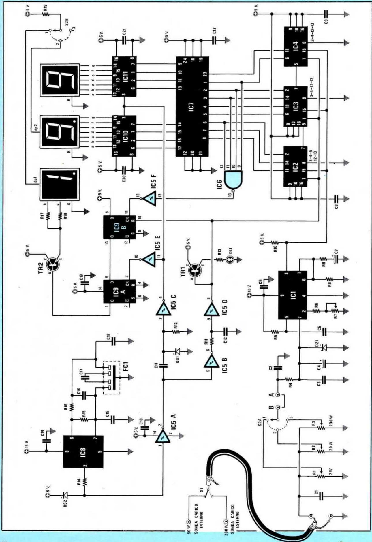
Fig. 4 Schema elettrico del wattmetro di AF. Nella lista dei componenti sono compresi anche quelli relativi allo stadio alimentatore il cui schema elettrico è visibile in fig. 5.
