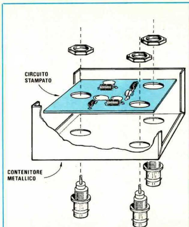
**Fig. 4** Il filtro dovrà risultare racchiuso entro una piccola scatola metallica per poterlo totalmente schermare. I tre bocchettoni BNC ci saranno utili per tenere bloccato il circuito stampato sul fondo della scatola come vedesi in disegno.
