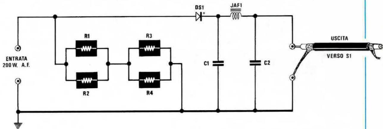
**Fig. 7** Per realizzare una sonda di carico da 200 e più watt è necessario collegare in serie-parallelo 4 resistenze da 52 ohm 50 watt. Tale sonda, per l'enorme quantità di calore generato, dovrà essere sistemata all'esterno del mobile e raffreddata ad olio, come vedesi in fig. 14-15.
