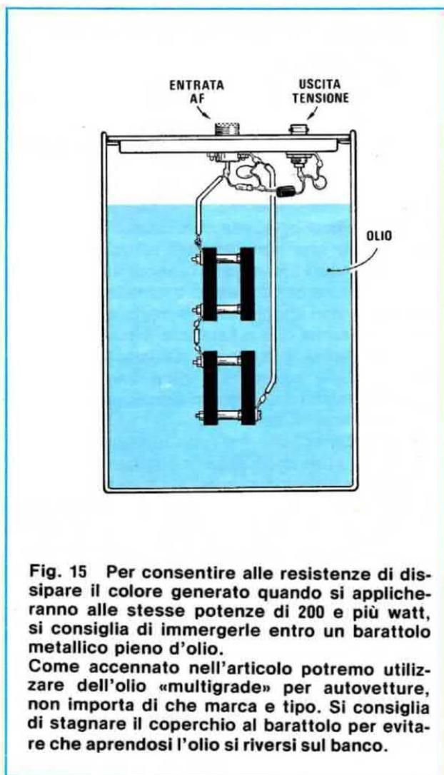
**Fig. 15** Per consentire alle resistenze di dissipare il calore generato quando si applicheranno alle stesse potenze di 200 e più watt, si consiglia di immergerle entro un barattolo metallico pieno d'olio. Come accennato nell'articolo potremo utilizzare dell'olio «multigrade» per autovetture, non importa di che marca e tipo. Si consiglia di stagnare il coperchio al barattolo per evitare che aprendosi l'olio si riversi sul banco.
