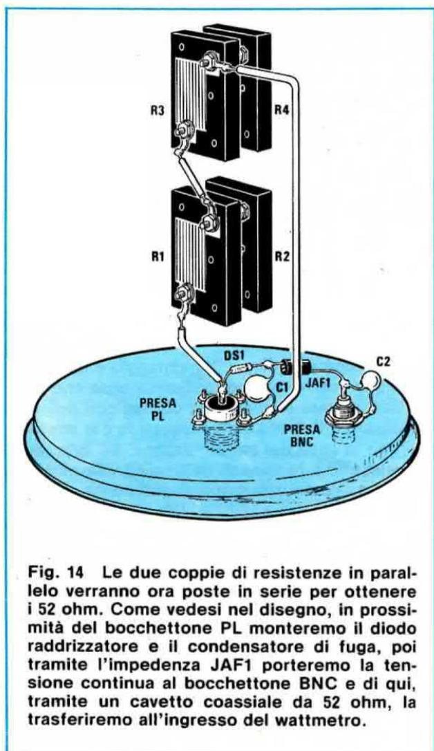
**Fig. 14** Le due coppie di resistenze in parallelo verranno ora poste in serie per ottenere i 52 ohm. Come vedesi nel disegno, in prossimità del bocchettone PL monteremo il diodo raddrizzatore e il condensatore di fuga, poi tramite l'impedenza JAF1 porteremo la tensione continua al bocchettone BNC e di qui, tramite un cavetto coassiale da 52 ohm, la trasferiremo all'ingresso del wattmetro.
