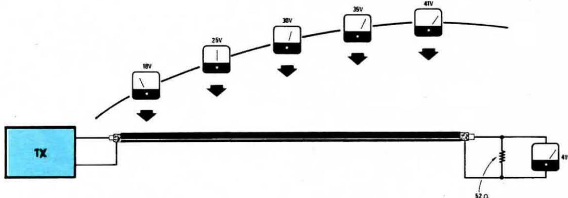
**Fig. 17** Se l'uscita del trasmettitore è disaccordata, sul cavo di trasferimento possono risultare presenti delle «onde stazionarie» pertanto avendosi dei ventri e dei nodi di tensione, a seconda della lunghezza del cavo impiegata, la tensione che misureremo risulterà ben diversa dal valore reale fornendoci così delle indicazioni errate sulla potenza.
