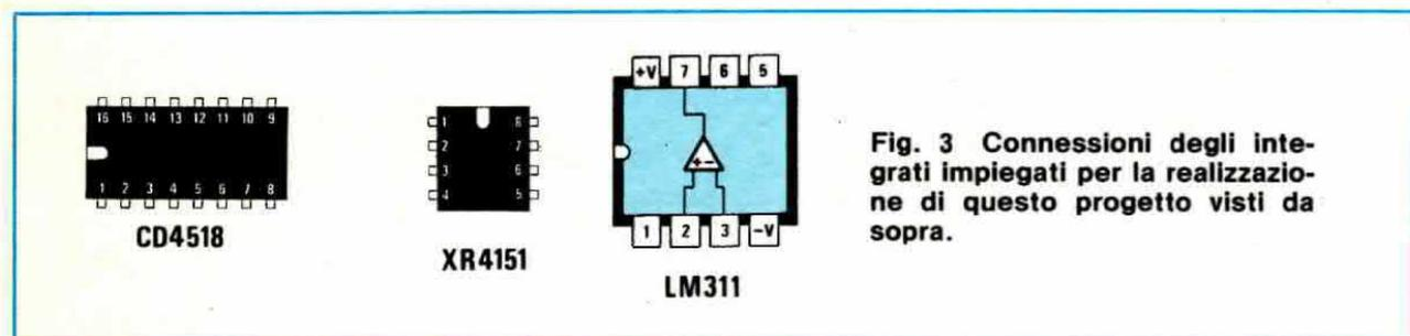
**Fig. 3 Connessioni degli integrati impiegati per la realizzazione di questo progetto visti da sopra.**
