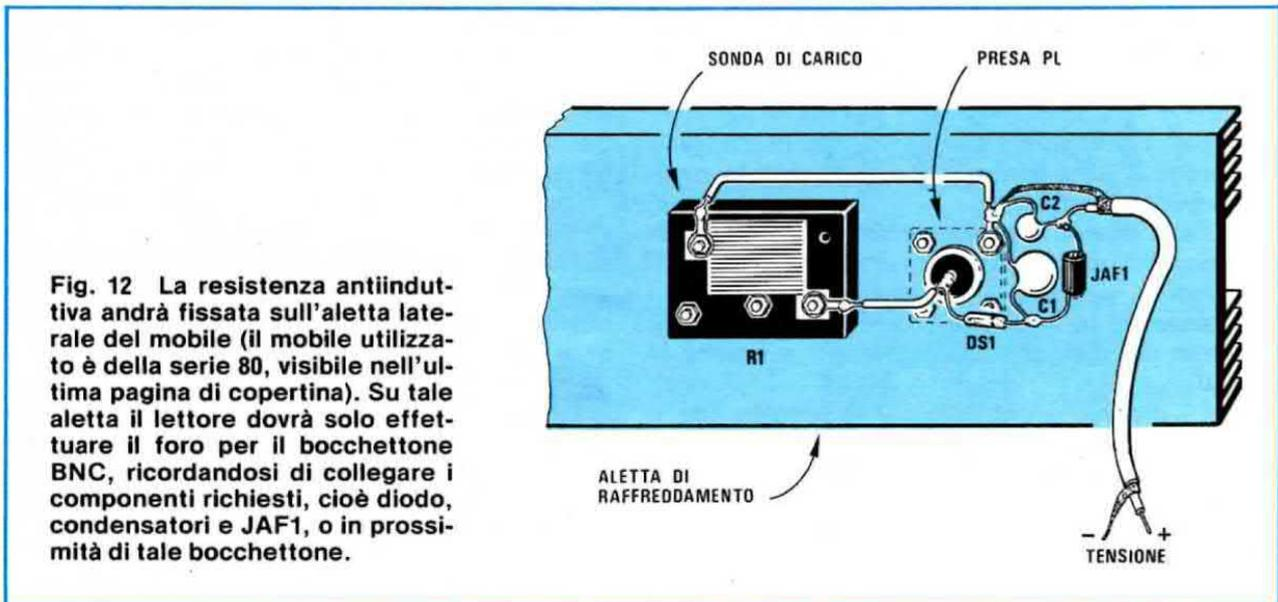
Fig. 12 La resistenza antiinduttiva andrà fissata sull'aletta laterale del mobile (il mobile utilizzato è della serie 80, visibile nell'ultima pagina di copertina). Su tale aletta il lettore dovrà solo effettuare il foro per il bocchettone BNC, ricordandosi di collegare i componenti richiesti, cioè diodo, condensatori e JAF1, o in prossimità di tale bocchettone.
