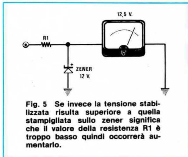
Fig. 5 Se invece la tensione stabilizzata risulta superiore a quella stampigliata sullo zener significa che il valore della resistenza R1 è troppo basso quindi occorrerà aumentarlo.
