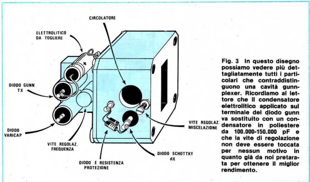
**Fig. 3** In questo disegno possiamo vedere più dettagliatamente tutti i particolari che contraddistinguono una cavità gunn-plexer. Ricordiamo al lettore che il condensatore elettrolitico applicato sul terminale del diodo gunn va sostituito con un condensatore in poliestere da 100.000-150.000 pF e che la vite di regolazione non deve essere toccata per nessun motivo in quanto già da noi preparata per ottenere il miglior rendimento.
