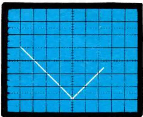
**Fig. 8** Se il controllo di bilanciamento sul preamplificatore è mal regolato vedremo apparire sullo schermo una V in cui le due linee laterali non hanno una identica ampiezza cioè avremo un tratto più lungo a destra o a sinistra.
