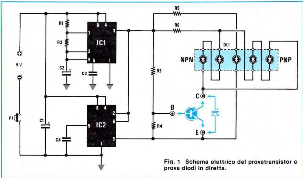
Fig. 1 Schema elettrico del provatransistor e prova diodi in diretta.
