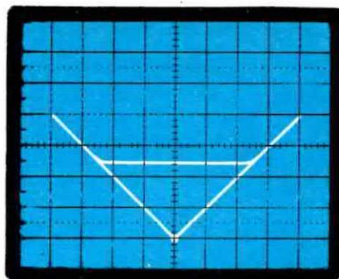
**Fig. 6** Se i due segnali applicati in ingresso, anziché risultare sfasati fra di loro di  $90^\circ$ , risultano sfasati di  $100-130-150$  gradi, vedremo il semiarco che congiungeva i due estremi della V abbassarsi progressivamente fino a coincidere con il vertice inferiore.
