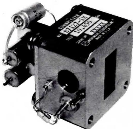
In questa foto si può vedere il terminale d'uscita del diodo Schottky completo di protezione (vedi diodo zener e relativa resistenza applicata in parallelo) nonché la vite che regola la miscelazione del segnale emesso dal diodo gunn con quello ricevuto dall'antenna. Si noti in prossimità della vite il foro in cui ha sede il circolatore.
