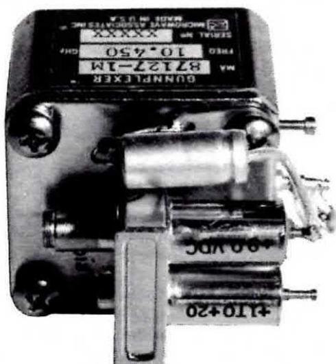
Sulla destra il gunn-plexer fotografato lateralmente. Come spiegato nell'articolo il condensatore elettrolitico da 50 mF 25 volt andrà sostituito con un condensatore poliestere da 100.000-150.000 pF in quanto la modulazione (per ottenere la stessa deviazione di frequenza su tutta la gamma) verrà effettuata direttamente sul diodo gunn.
