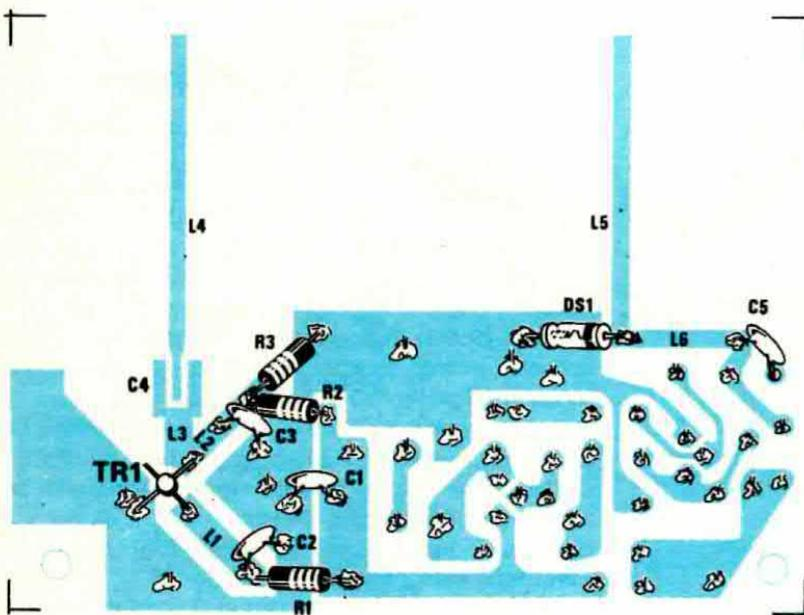
Fig. 7 Schema pratico di montaggio dello stadio ricetrasmittente visto dalla parte del transistor BFQ.88. Quando stagnerete il diodo Schottky DS1 fate attenzione che la fascia di colore presente sul suo involucro risulti rivolta come in disegno. Nota: il secondo terminale E del transistor BFQ.88, che non stagneremo sul circuito stampato, andrà ripiegato a L in modo da allontanarlo dalla vetronite.
