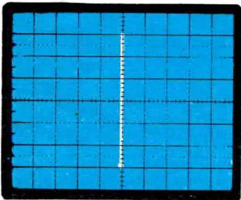
**Fig. 3** Applicando su entrambi gli ingressi destro e sinistro del nostro vettorscope un identico segnale di BF (segnale mono) sullo schermo dell'oscilloscopio vedremo apparire una linea verticale di ampiezza doppia rispetto alle precedenti.
