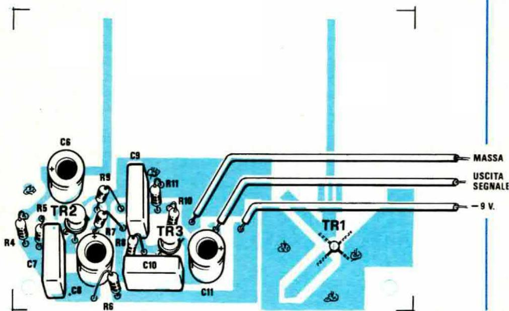
Fig. 8 Sul lato opposto del circuito stampato monteremo i restanti componenti richiesti dal modulo radar tenendo presente che le resistenze vanno collocate in posizione verticale come vedesi in disegno.
