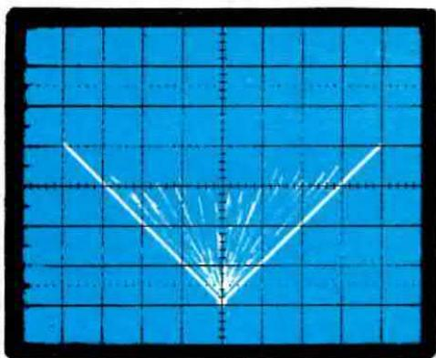
**Fig. 7** Collegando gli ingressi del vettroscope alle uscite di un preamplificatore e visualizzando sullo schermo il segnale relativo a un disco o nastro stereo (musica o parlato) vedremo ancora apparire la V riportata in fig. 4 però con tante righe supplementari al centro.
