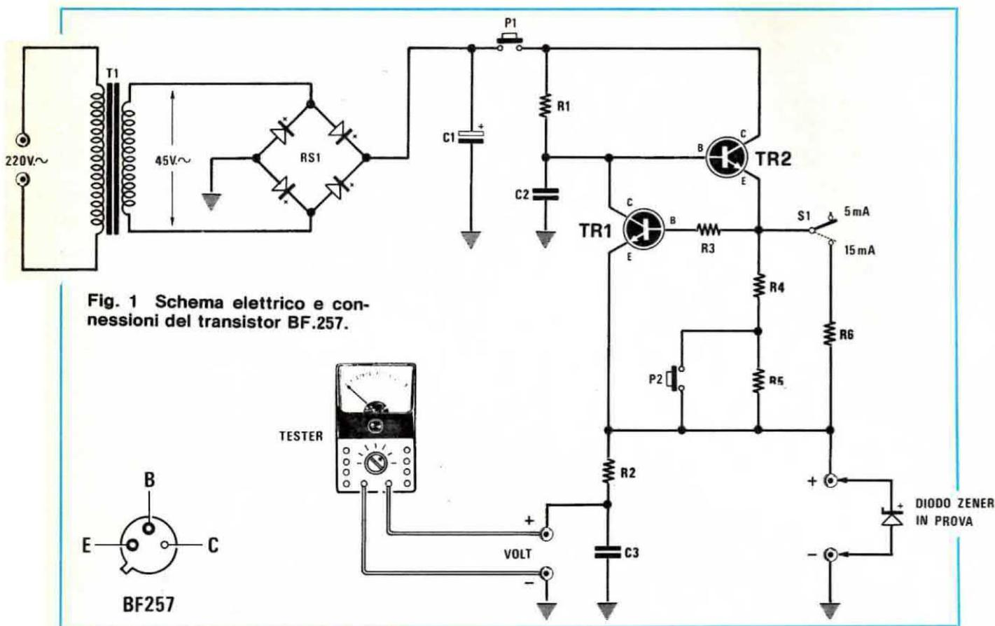
Fig. 1 Schema elettrico e connessioni del transistor BF.257.
