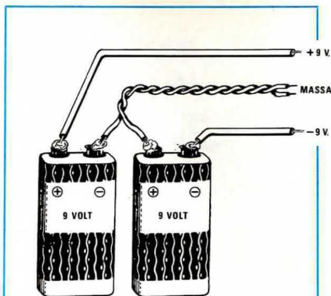
**Fig. 13** Considerato il basso assorbimento di questo circuito, per alimentarlo consigliamo di impiegare due normali pile da 9 volt collegandole in serie come indicato nel disegno. Per evitare di alimentare il circuito in modo errato sarà bene utilizzare un filo rosso per il positivo dei 9 volt, un filo nero per il negativo e un filo bianco-giallo o verde per la massa.
