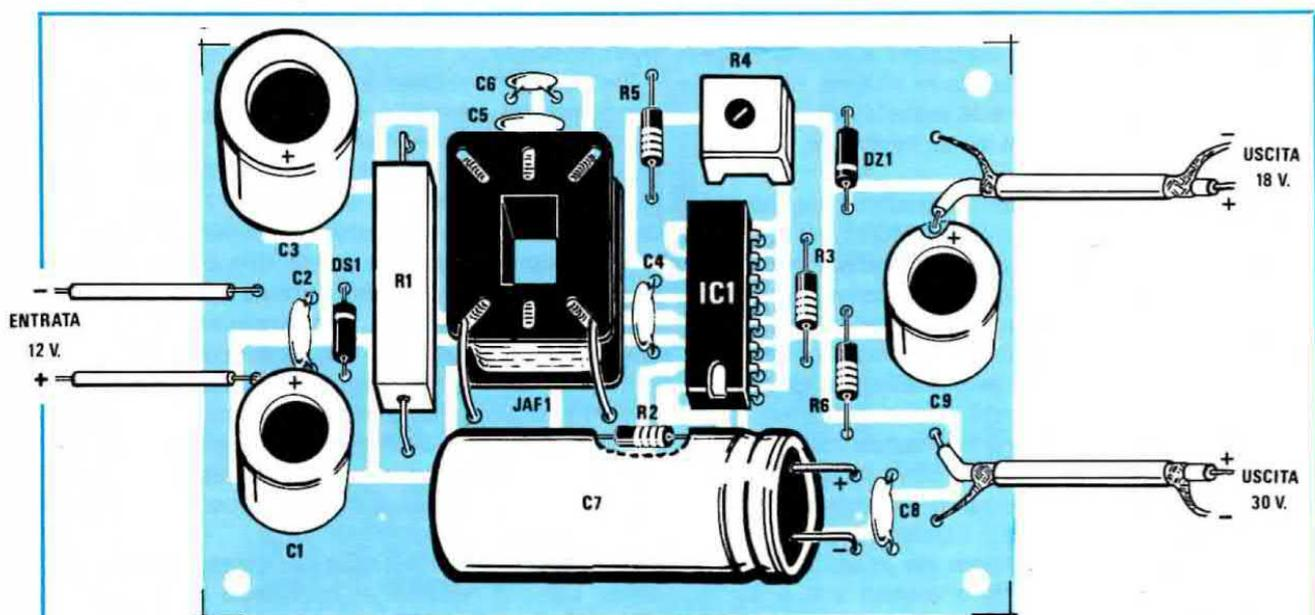
**Fig. 13** In alto lo schema pratico di montaggio del circuito elevatore di tensione LX424 il cui schema elettrico è riportato in fig. 7. Questo circuito, come vedesi dalla foto qui a fianco, andrà racchiuso dentro un piccolo contenitore metallico per poterlo totalmente schermare. Si noti l'impedenza JAF1 che fisseremo sul circuito stampato con collante cementatutto.
