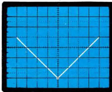
**Fig. 4** Applicando sui due ingressi destro e sinistro del nostro vettorscope due segnali di identica ampiezza e frequenza, però sfasati fra di loro esattamente di  $180^\circ$  (segnale stereo) vedremo apparire sullo schermo dell'oscilloscopio una V.
