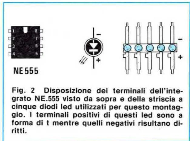
Fig. 2 Disposizione dei terminali dell'integrato NE.555 visto da sopra e della striscia a cinque diodi led utilizzati per questo montaggio. I terminali positivi di questi led sono a forma di T mentre quelli negativi risultano diritti.
