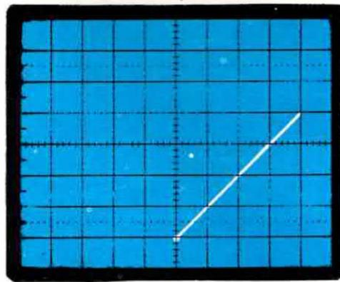
**Fig. 2** Applicando lo stesso segnale di BF a frequenza costante sull'ingresso del canale destro vedremo apparire sullo schermo la stessa linea riportata in fig. 1 questa volta però inclinata sulla destra.
