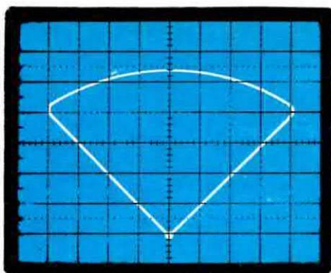
**Fig. 5** Applicando sui due ingressi del vettroscope due segnali di identica ampiezza e frequenza però sfasati fra di loro di  $90^\circ$  sullo schermo dell'oscilloscopio ci apparirà ancora una V però con gli estremi superiori collegati da una specie di semiarco.
