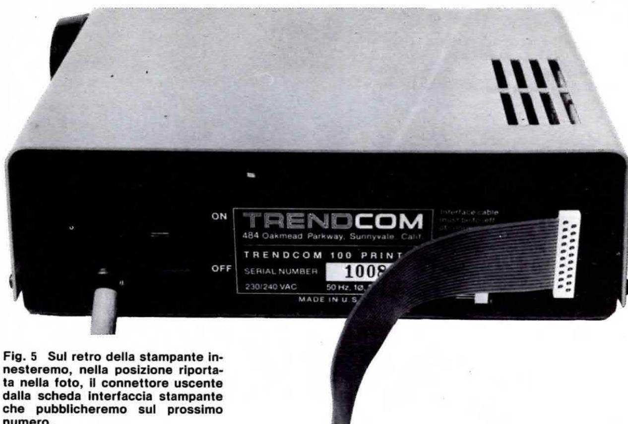
**Fig. 5** Sul retro della stampante innesteremo, nella posizione riportata nella foto, il connettore uscente dalla scheda interfaccia stampante che pubblicheremo sul prossimo numero.
