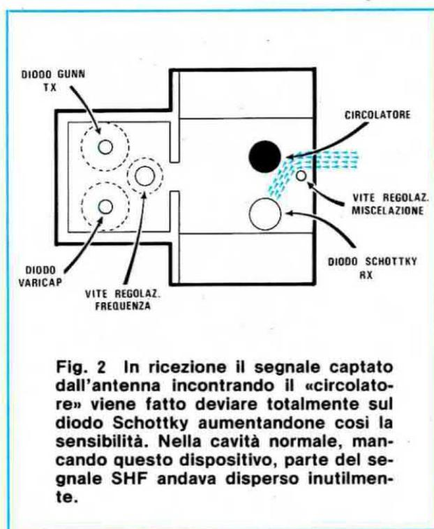
percentuale del segnale di SHF emesso dal diodo gunn più che sufficiente per consentire a questo di svolgere le sue funzioni di convertitore-miscelatore SHF senza necessità di doverlo polarizzare in continua come avveniva invece per la cavità standard.
