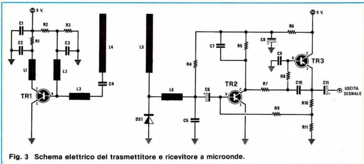
Fig. 3 Schema elettrico del trasmettitore e ricevitore a microonde.
