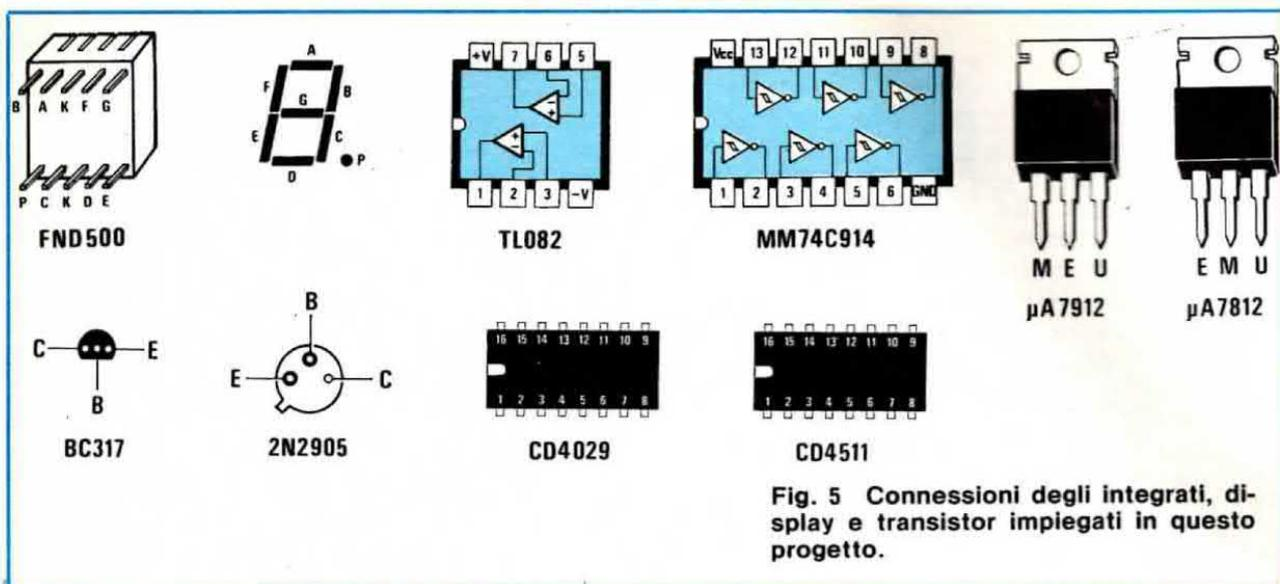
Fig. 5 Connessioni degli integrati, display e transistor impiegati in questo progetto.
