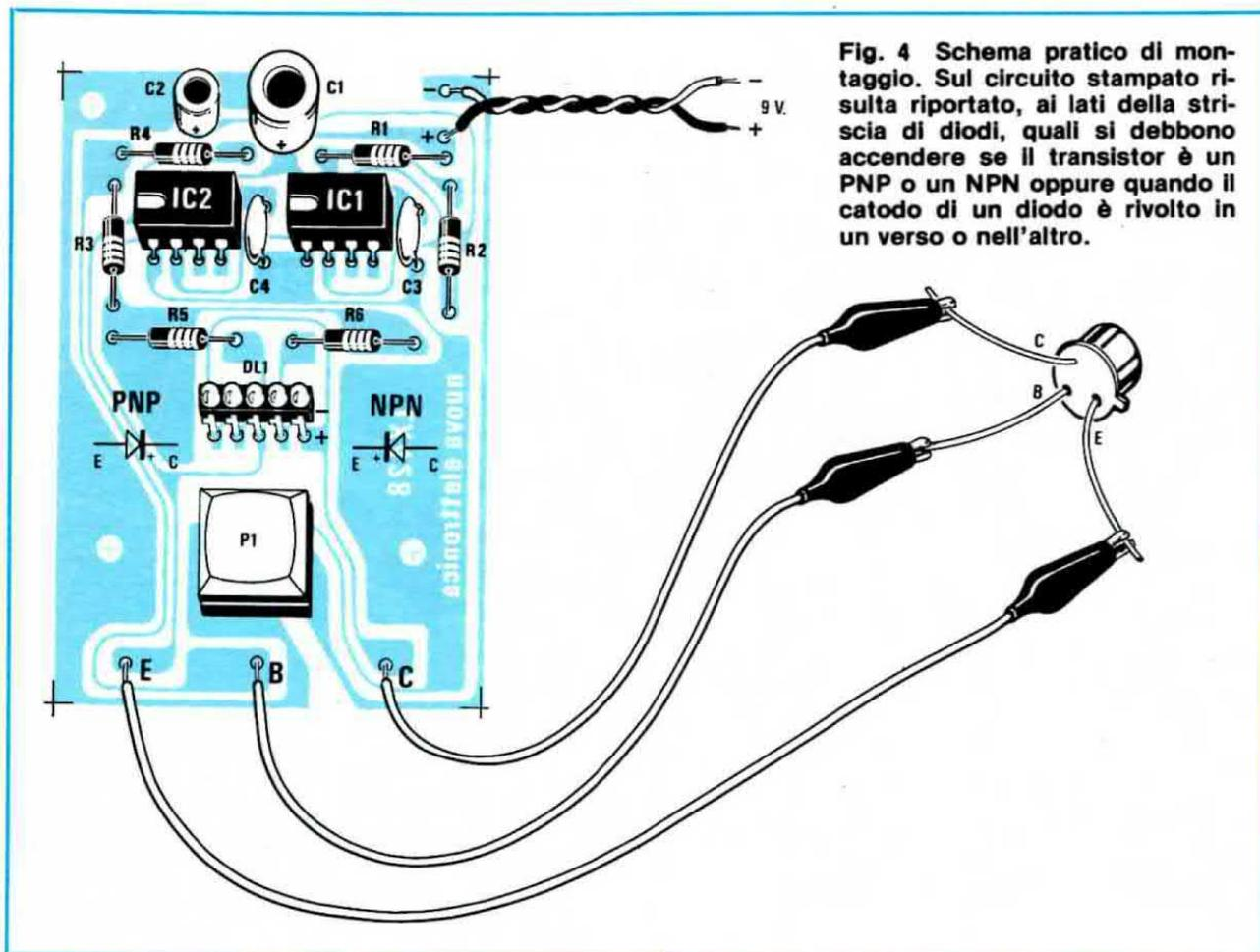
Fig. 4 Schema pratico di montaggio. Sul circuito stampato risulta riportato, ai lati della striscia di diodi, quali si debbono accendere se il transistor è un PNP o un NPN oppure quando il catodo di un diodo è rivolto in un verso o nell'altro.
