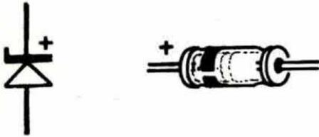
**Fig. 6** Per distinguere il terminale del diodo zener che va collegato al positivo della tensione da stabilizzare, è sempre riportata sull'involucro una fascia di colore. Nel simbolo elettrico questo terminale corrisponde al lato in cui è presente il trattino orizzontale sopra il vertice del triangolo.
