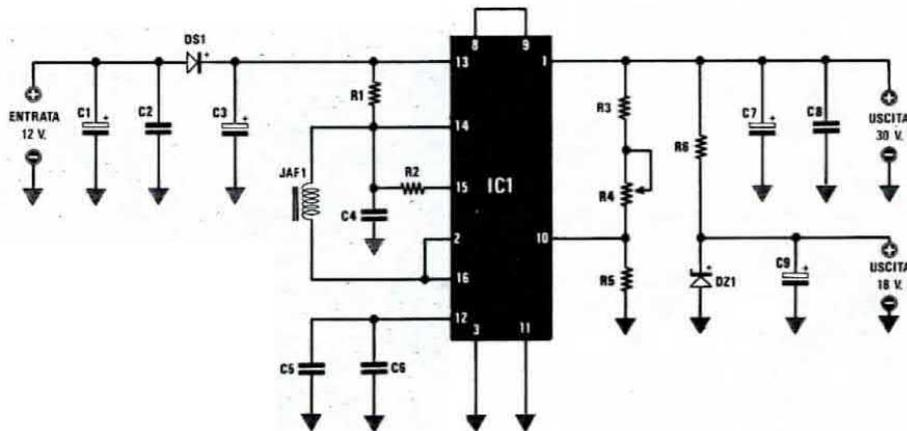
Fig. 7 Schema elettrico dell'elevatore di tensione. Questo circuito andrà racchiuso dentro una piccola scatola di alluminio per evitare che influenzi gli altri stadi.
