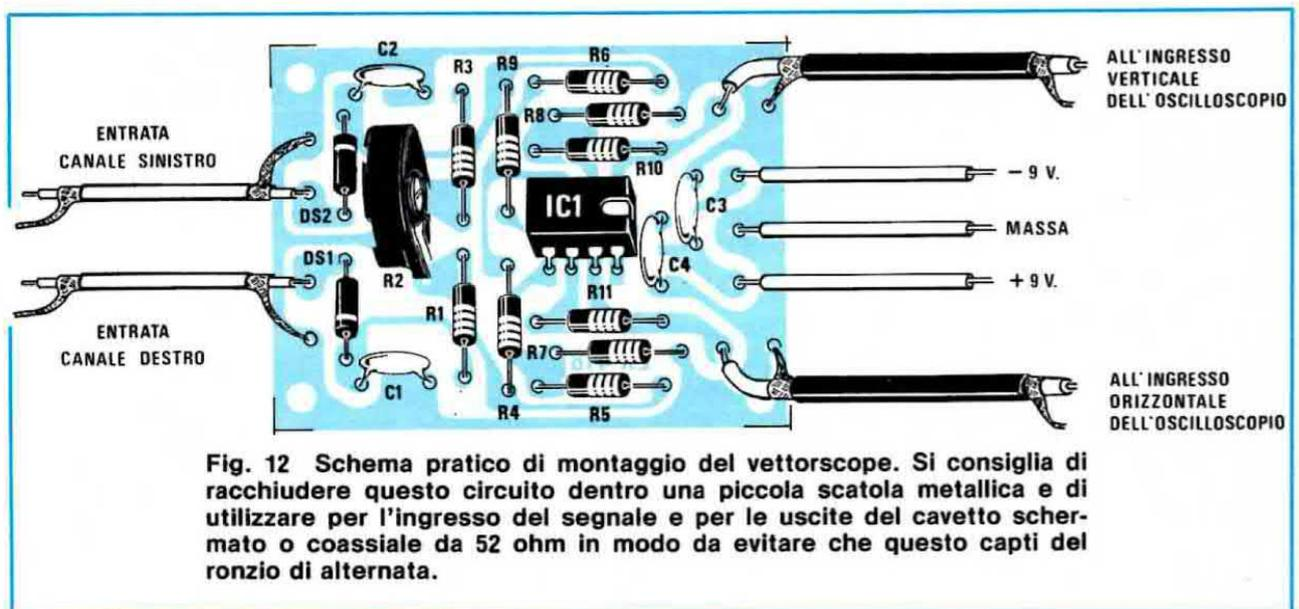
**Fig. 12** Schema pratico di montaggio del vettroscope. Si consiglia di racchiudere questo circuito dentro una piccola scatola metallica e di utilizzare per l'ingresso del segnale e per le uscite del cavetto schermato o coassiale da 52 ohm in modo da evitare che questo capti del ronzio di alternata.
