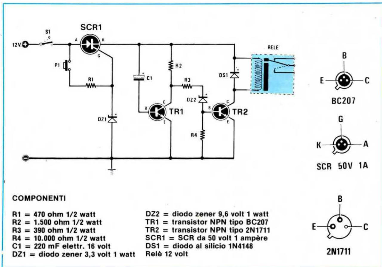
cui contatti piloteranno una sirena o campanello di allarme. Durante la fase di preallarme il proprietario dell'appartamento, quando rientra, avrà tutto il tempo di disinnescare il circuito aprendo il deviatore S1 prima che questo entri in funzione.
