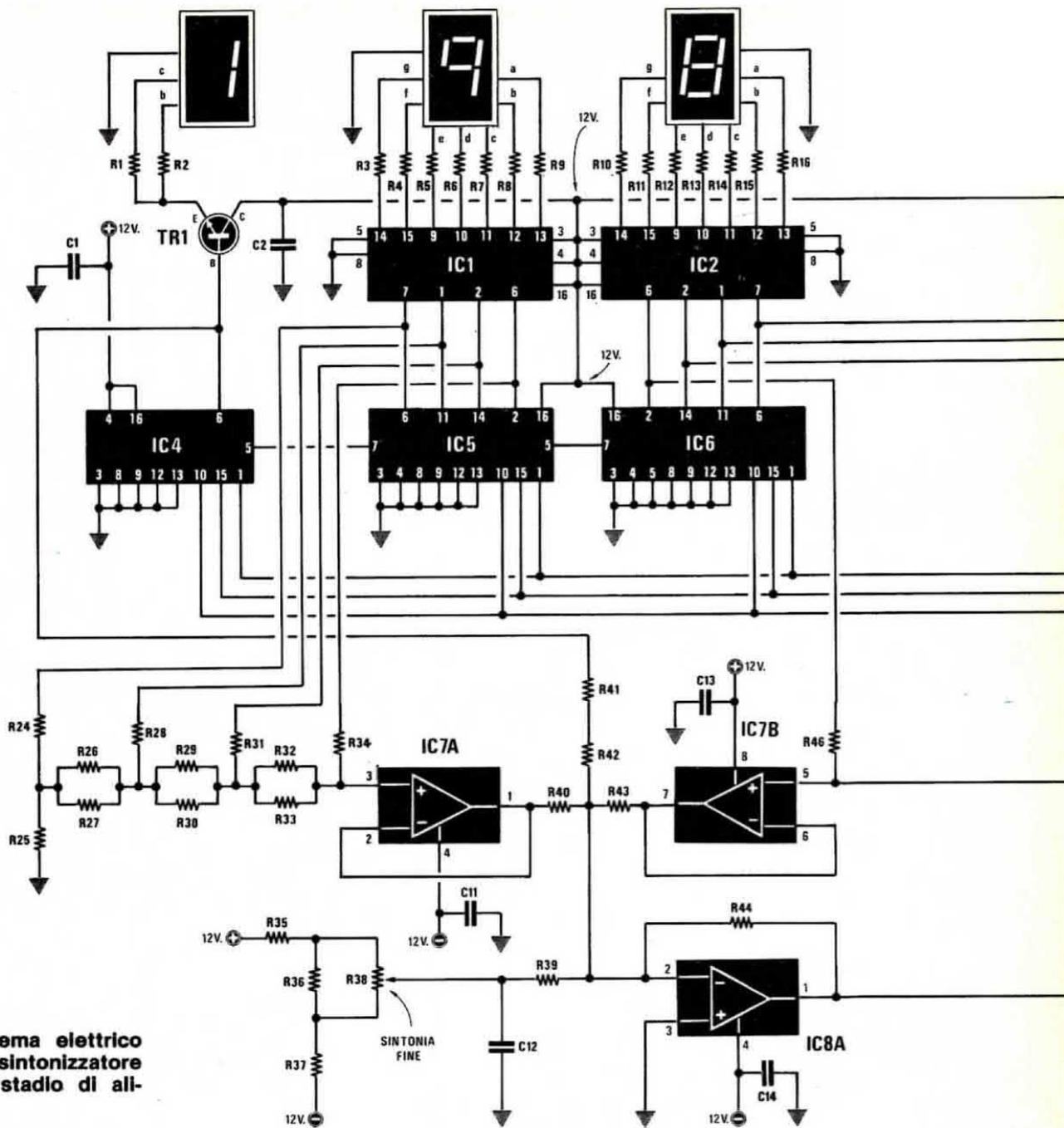
**Fig. 3** Schema elettrico del nostro sintonizzatore escluso lo stadio di alimentazione.
