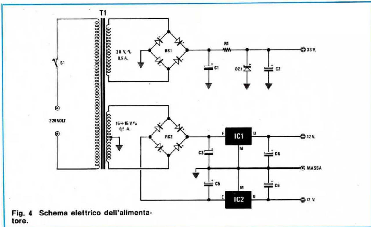
Fig. 4 Schema elettrico dell'alimentatore.
