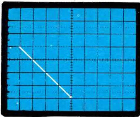
**Fig. 1** Applicando sul solo ingresso di «sinistra» un segnale di BF a frequenza costante, sullo schermo dell'oscilloscopio apparirà una linea inclinata a sinistra la cui lunghezza è subordinata all'ampiezza del segnale applicato.
