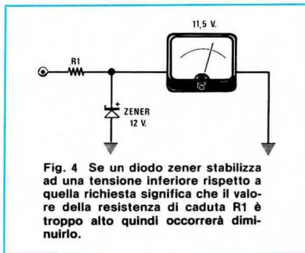
Fig. 4 Se un diodo zener stabilizza ad una tensione inferiore rispetto a quella richiesta significa che il valore della resistenza di caduta R1 è troppo alto quindi occorrerà diminuirlo.
