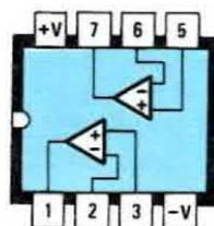
Fig. 2 Connessioni dell'integrato MC.1458.
