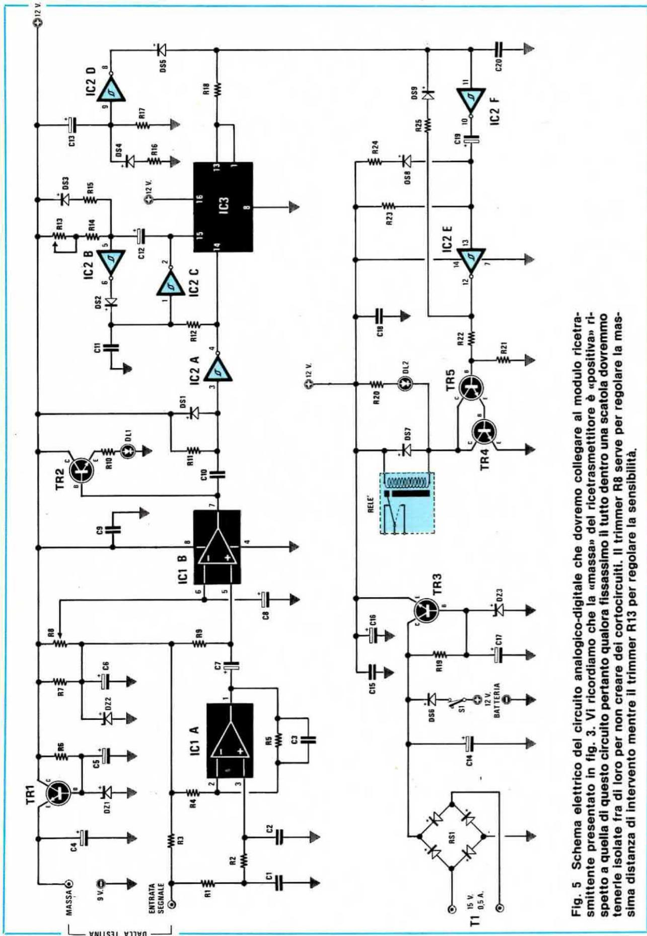
Fig. 5 Schema elettrico del circuito analogico-digitale che dovremo collegare al modulo rice-trasmittente presentato in fig. 3. Vi ricordiamo che la «massa» del rice-trasmittitore è «positiva» rispetto a quella di questo circuito pertanto qualora fississimo il tutto dentro una scatola dovremmo tenerle isolate fra di loro per non creare dei cortocircuiti. Il trimmer R8 serve per regolare la massima distanza di intervento mentre il trimmer R13 per regolare la sensibilità.
