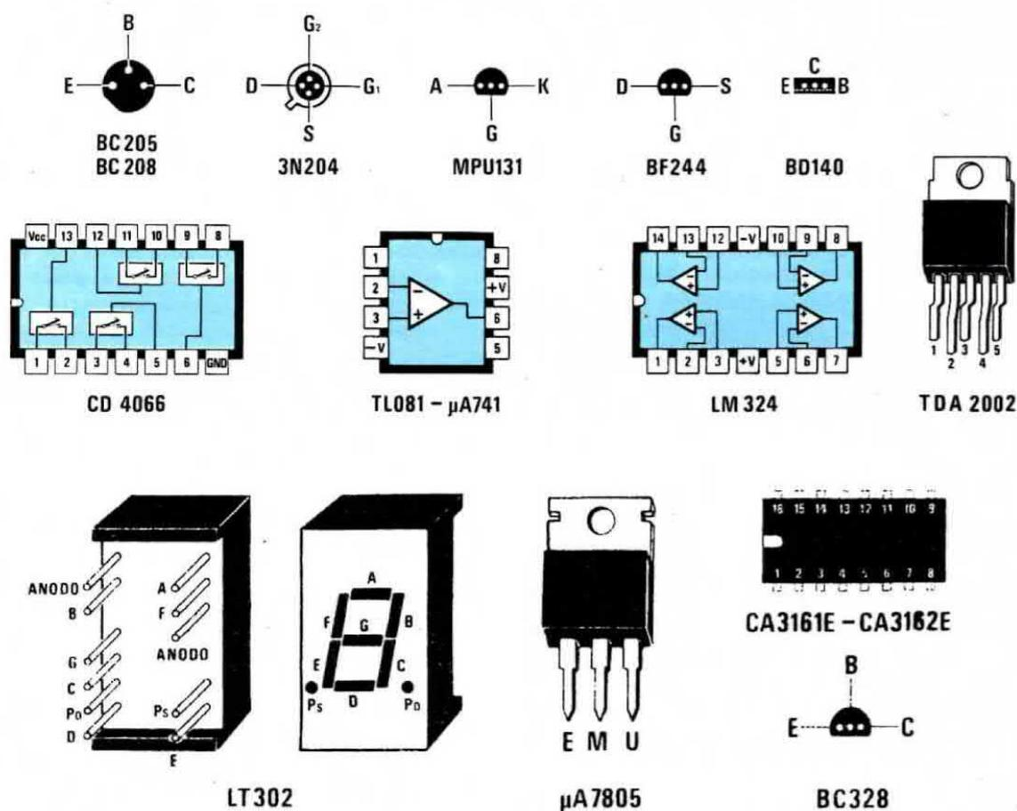
Fig. 9 Connessioni dei transistor (visti da sotto) e degli integrati (visti da sopra) impiegati per la realizzazione di questo progetto.
