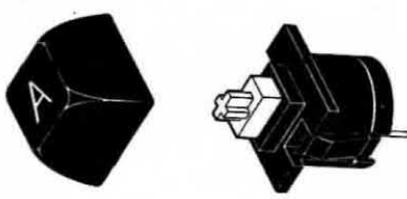
**Fig. 2** La barra dell'interlinea dispone di una base che andrà fissata al circuito stampato. Sopra a questa si appoggerà il ferro sagomato ai cui estremi dovremo infilare i due supporti in plastica che innesteremo poi a pressione negli appositi vani agli estremi della barra stessa come vedesi in disegno.
