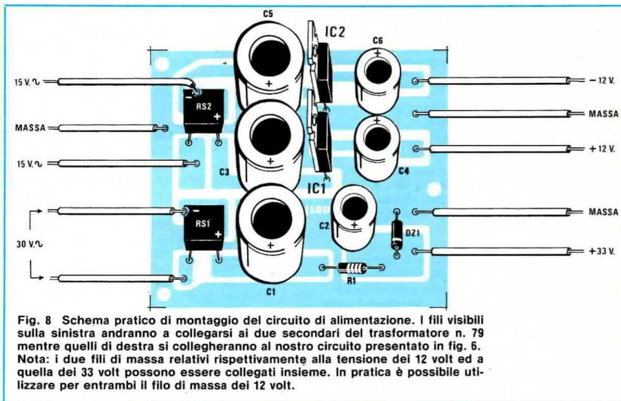
**Fig. 8** Schema pratico di montaggio del circuito di alimentazione. I fili visibili sulla sinistra andranno a collegarsi ai due secondari del trasformatore n. 79 mentre quelli di destra si collegheranno al nostro circuito presentato in fig. 6. **Nota:** i due fili di massa relativi rispettivamente alla tensione dei 12 volt ed a quella dei 33 volt possono essere collegati insieme. In pratica è possibile utilizzare per entrambi il filo di massa dei 12 volt.
