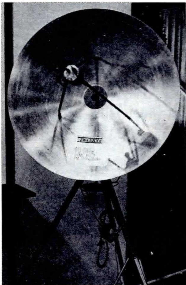
La cavità gunn-plexer, congiunta al nostro preamplificatore LX368, si presta per essere applicata anche ad un'antenna parabolica in modo da aumentare il guadagno. Prossimamente forniremo al lettore un contenitore per racchiudere tale preamplificatore e il gunn-plexer con tutti i consigli necessari per ottenere, da un simile accoppiamento, il massimo della resa.
