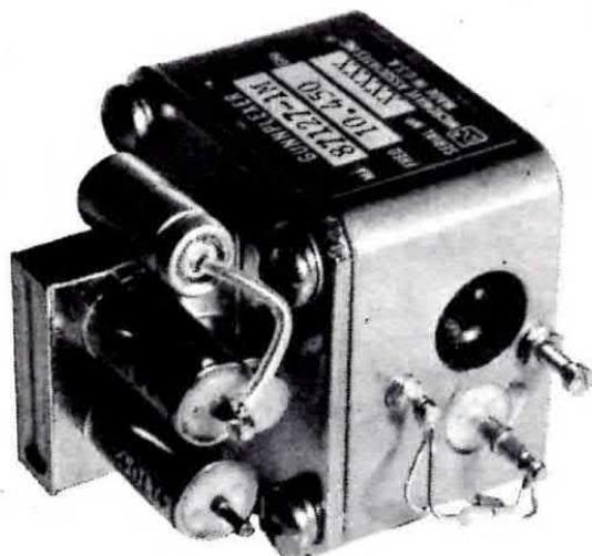
In questa foto scattata frontalmente è possibile vedere in basso il diodo Schottky del ricevitore e sopra a questo il cilindro magnetico del circolatore in grado di creare nell'interno della cavità un particolare campo magnetico necessario per far compiere alle microonde, sia in trasmissione che in ricezione, un percorso ben determinato. Sull'imboccatura di questa cavità potremo applicare una delle antenne a tromba presentate sul n. 66 di Nuova Elettronica.
