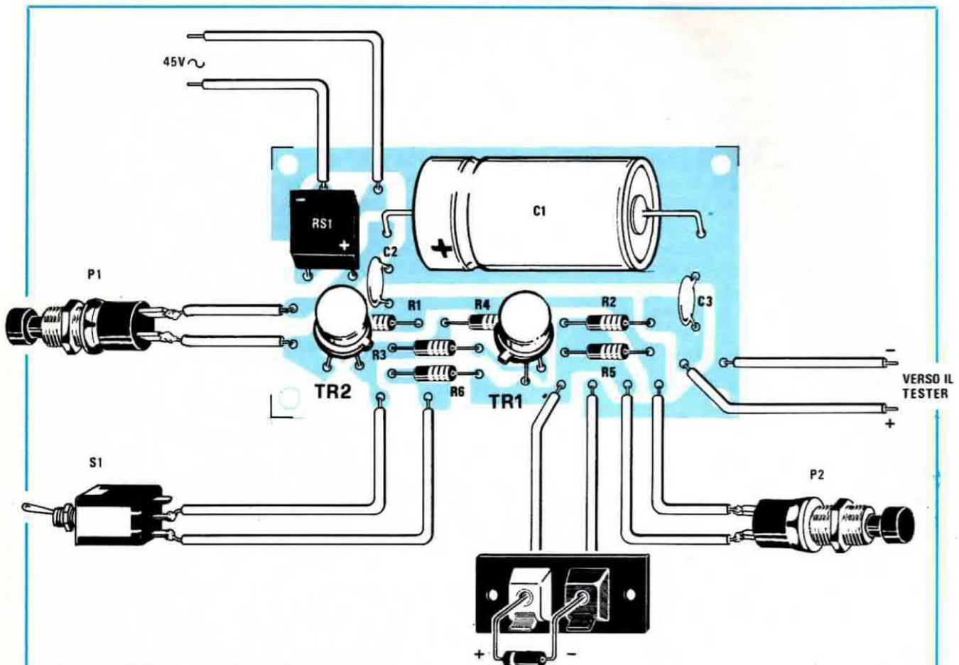
**Fig. 3** Schema pratico di montaggio del prova-zener. I due fili posti in alto a sinistra con l'indicazione 45 volt alternati andranno collegati al secondario del trasformatore n. 80 mentre i due sulla destra ad un normalissimo tester predisposto per la misura in tensione continua.
