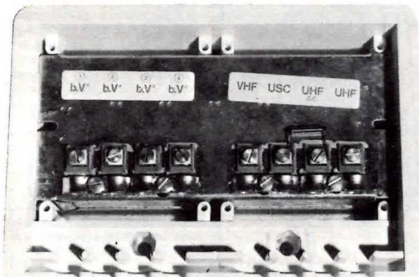
Foto del preamplificatore-miscelatore idoneo per ricevere in ingresso i segnali di quattro antenne UHF per la banda 5° più una VHF e altre due antenne UHF per la banda 4°.
