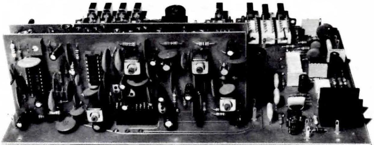
Questa foto scattata posteriormente ci mostra il telaio del ricevitore a banda larga +PLL siglato LX422 come si presenta una volta innestato sul connettore femmina presente nel circuito base. Si può notare come i componenti di questo telaio risultano disposti verso l'esterno della piastra madre, mentre quelli del secondo telaio risultano disposti verso l'interno.
