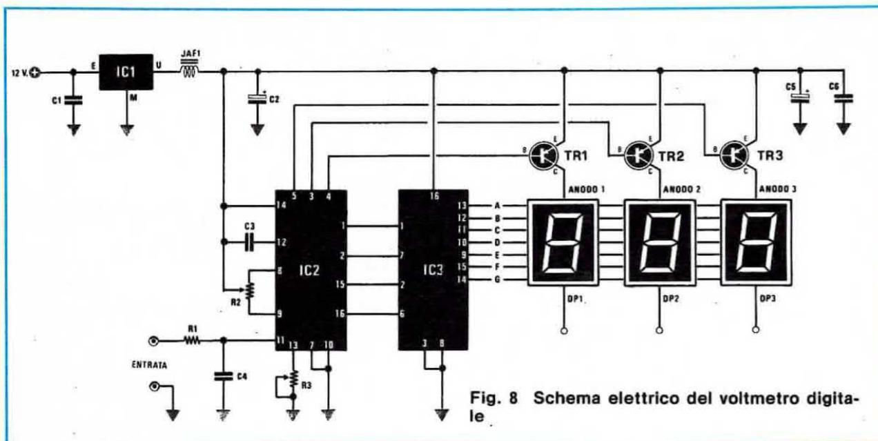
Fig. 8 Schema elettrico del voltmetro digitale
