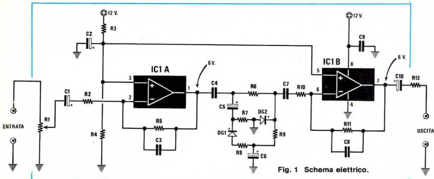
Fig. 1 Schema elettrico.
