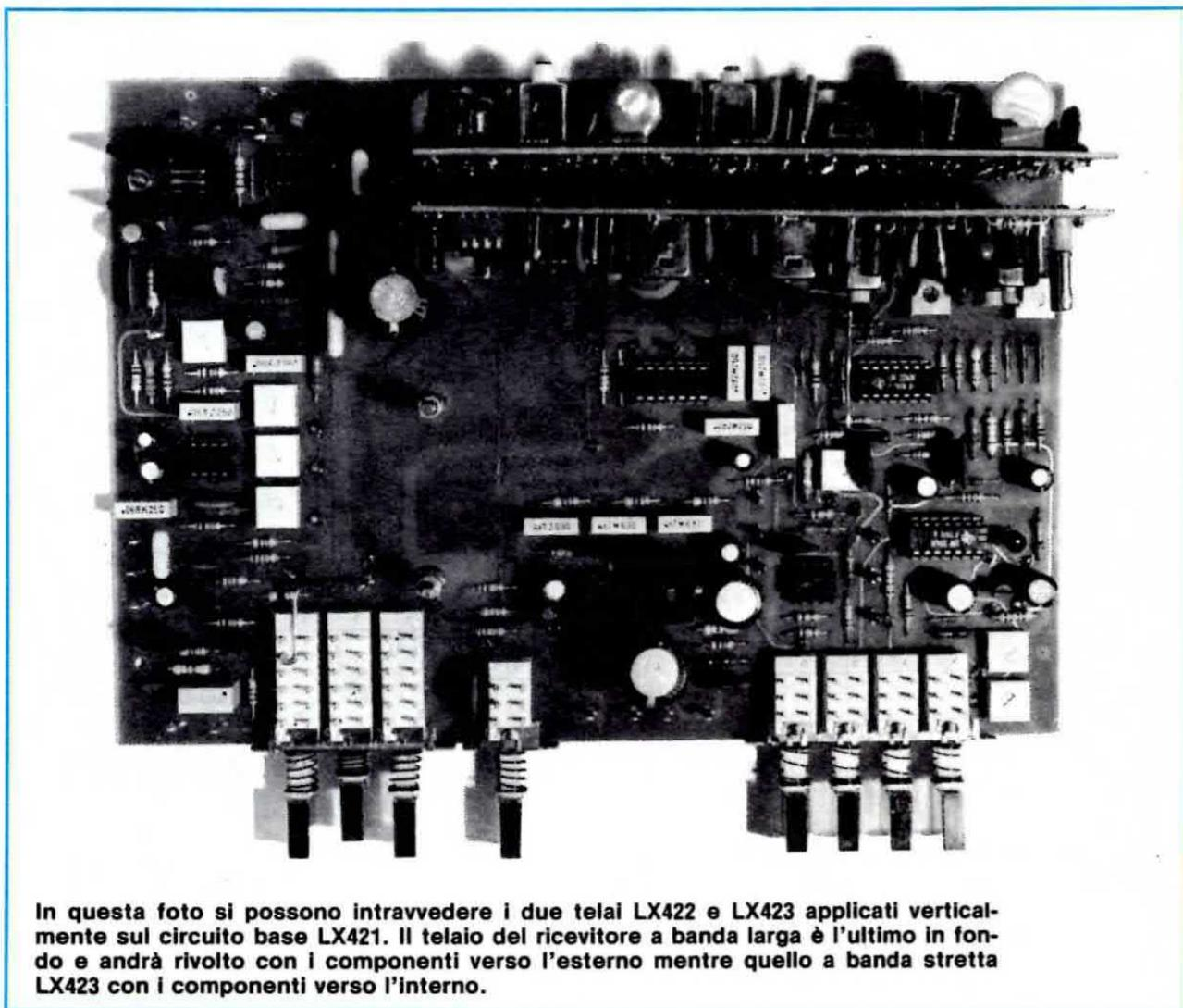
In questa foto si possono intravedere i due telai LX422 e LX423 applicati verticalmente sul circuito base LX421. Il telaio del ricevitore a banda larga è l'ultimo in fondo e andrà rivolto con i componenti verso l'esterno mentre quello a banda stretta LX423 con i componenti verso l'interno.
