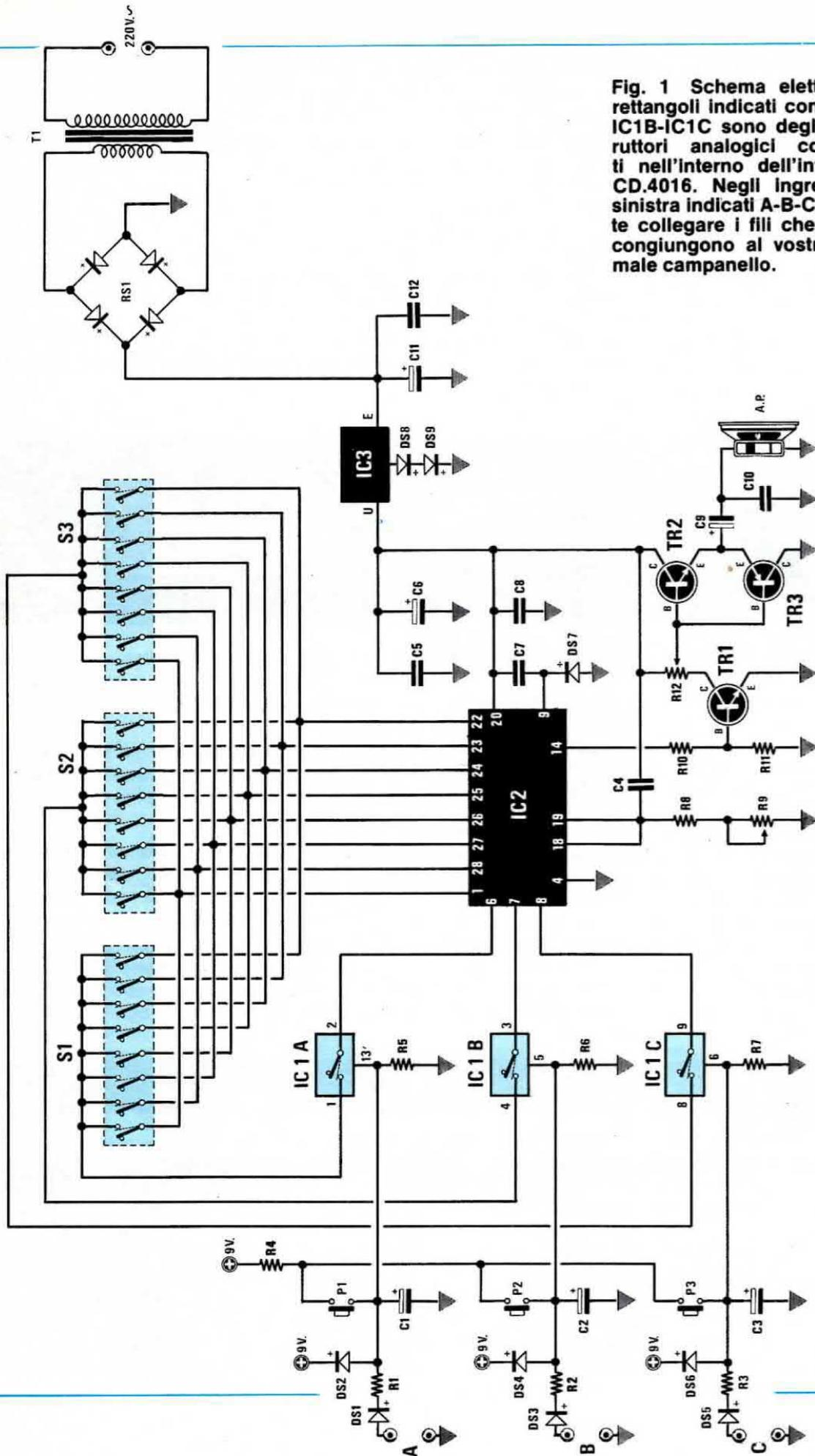
Fig. 1 Schema elettrico. I rettangoli indicati con IC1A-IC1B-IC1C sono degli interruttori analogici contenuti nell'interno dell'integrato CD.4016. Negli ingressi di sinistra indicati A-B-C dovrete collegare i fili che ora si congiungono al vostro normale campanello.
