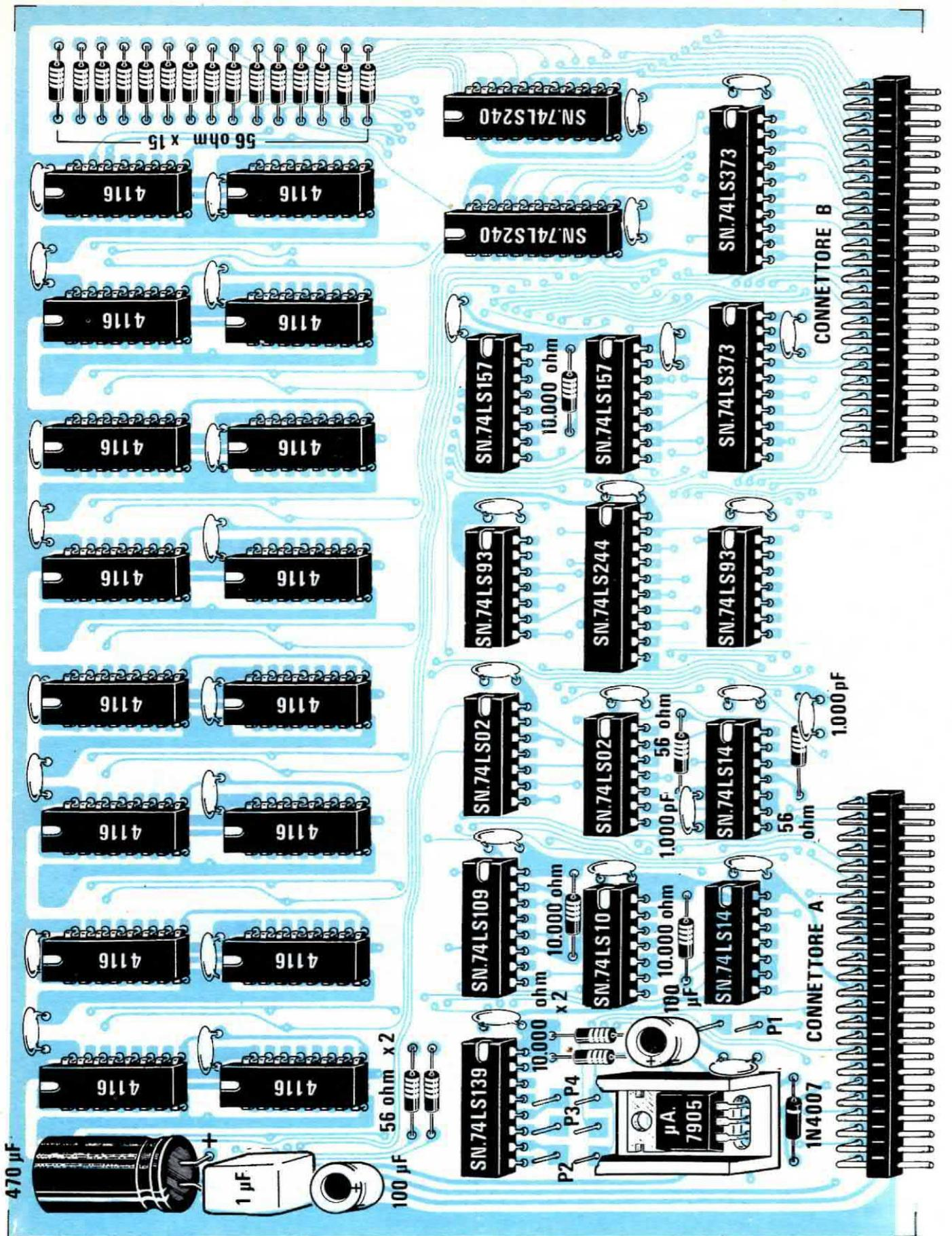
Fig. 2 Schema pratico di montaggio. Si notino sopra l'integrato stabilizzatore  $\mu\text{A.7905}$  e tre ponticelli P2-P3-P4 che dovremo cortocircuitare a seconda della configurazione utilizzata nel micro (vedi tabella 1 a pag. 115). NOTA: i condensatori a disco per i quali non è indicato il valore risultano da 100.000 pF.
