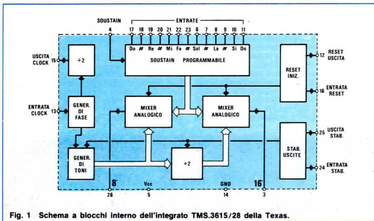
Fig. 1 Schema a blocchi interno dell'integrato TMS.3615/28 della Texas.
