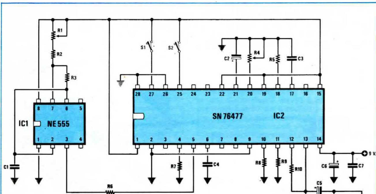
Fig. 1 Schema elettrico del circuito dal quale potremo ricavarci rumori di cavalli al galoppo, elicotteri o mitragliatrici a nostra scelta agendo semplicemente sui due trimmer R1 ed R4, nonchè sui deviatori S1-S2.
