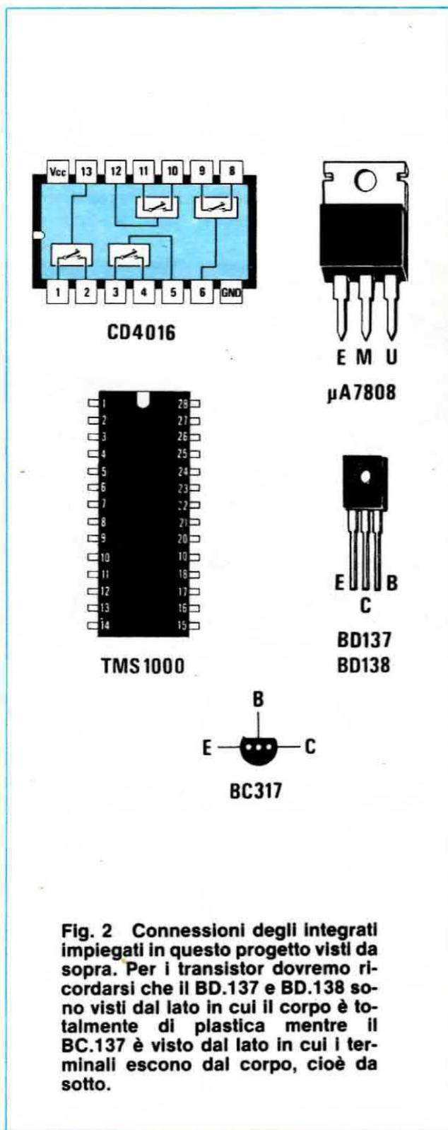
Fig. 2 Connessioni degli integrati impiegati in questo progetto visti da sopra. Per i transistor dovremo ricordarsi che il BD.137 e BD.138 sono visti dal lato in cui il corpo è totalmente di plastica mentre il BC.137 è visto dal lato in cui i terminali escono dal corpo, cioè da sotto.
