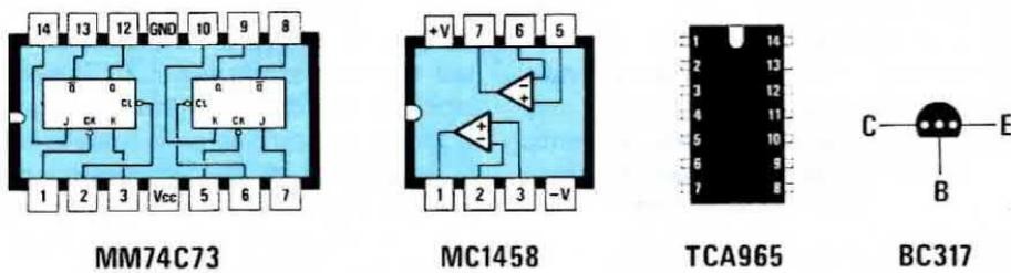
**Fig. 3** Connessioni degli integrati (visti da sopra) e del transistor (visto invece da sotto) impiegati in questo progetto. Per gli integrati si raccomanda di utilizzare i relativi zoccoli in modo tale che sia più facile sostituirli in caso di guasto.
