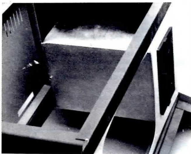
**Fig. 9** Se nell'interno del mobile il floppy non risulta schermato con una lamiera a U, il giogo di deflessione del monitor video lo può influenzare impedendone così il regolare funzionamento. Nella foto di sinistra si può vedere tale schermo applicato dentro il mobile.
