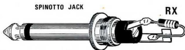
**Fig. 5** Come spiegato nell'articolo, per realizzare la nostra «chiave» potremo utilizzare un comunissimo spinotto jack collegando fra i due terminali di questo una resistenza  $R_x$  di valore esattamente identico a quello impiegato per  $R_3$  in modo da poter bilanciare perfettamente il ponte posto sugli ingressi di IC1.
