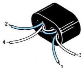
**Fig. 10** Disegno a grandezza naturale del circuito stampato LX466 e del trasformatore di accoppiamento T1 avvolto su nucleo in ferrite. Ricordatevi che i due avvolgimenti vanno effettuati con filo bifilare e collegati al circuito stampato in modo che risultino in opposizione di fase come riportato nello schema elettrico.
