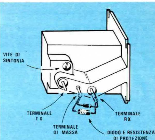
**Fig. 2** Guardando la cavità di lato, il terminale del diodo trasmittente è posto sulla sinistra (vedi terminale indicato TX) mentre quello del diodo ricevente sulla destra (vedi terminale RX). Il terminale centrale è quello di MASSA che dovrà essere collegato alla massa del circuito stampato. Il diodo e la resistenza collegati tra il terminale RX e la massa servono per proteggere il diodo Schottky da scariche elettrostatiche.
