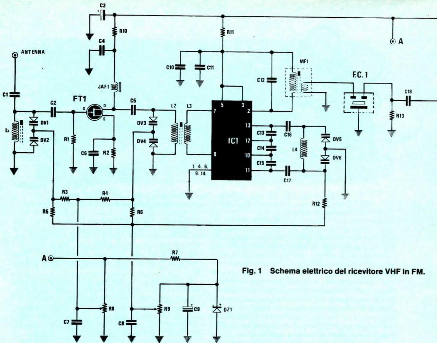
Fig. 1 Schema elettrico del ricevitore VHF in FM.
