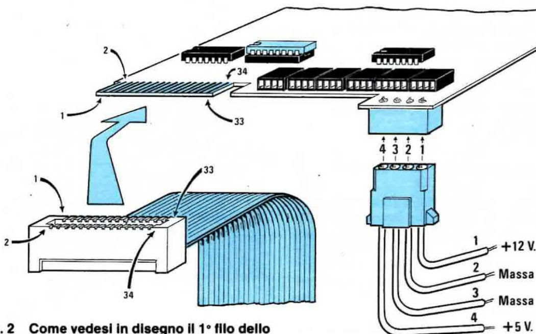
**Fig. 2** Come vedesi in disegno il 1° filo dello spinotto di alimentazione serve per i 12 volt positivi, i fili 2-3 sono di massa, mentre il filo 4 serve per i 5 volt positivi. Ricordarsi, quando si infila sulla sinistra il connettore della piattina a 34 fili, di controllare che i numeri 1-33 si trovino posti in basso e i numeri 2-34 in alto, diversamente provocheremo dei cortocircuiti in quanto tutte le piste inferiori (dall'1 al 33) sono di massa.
