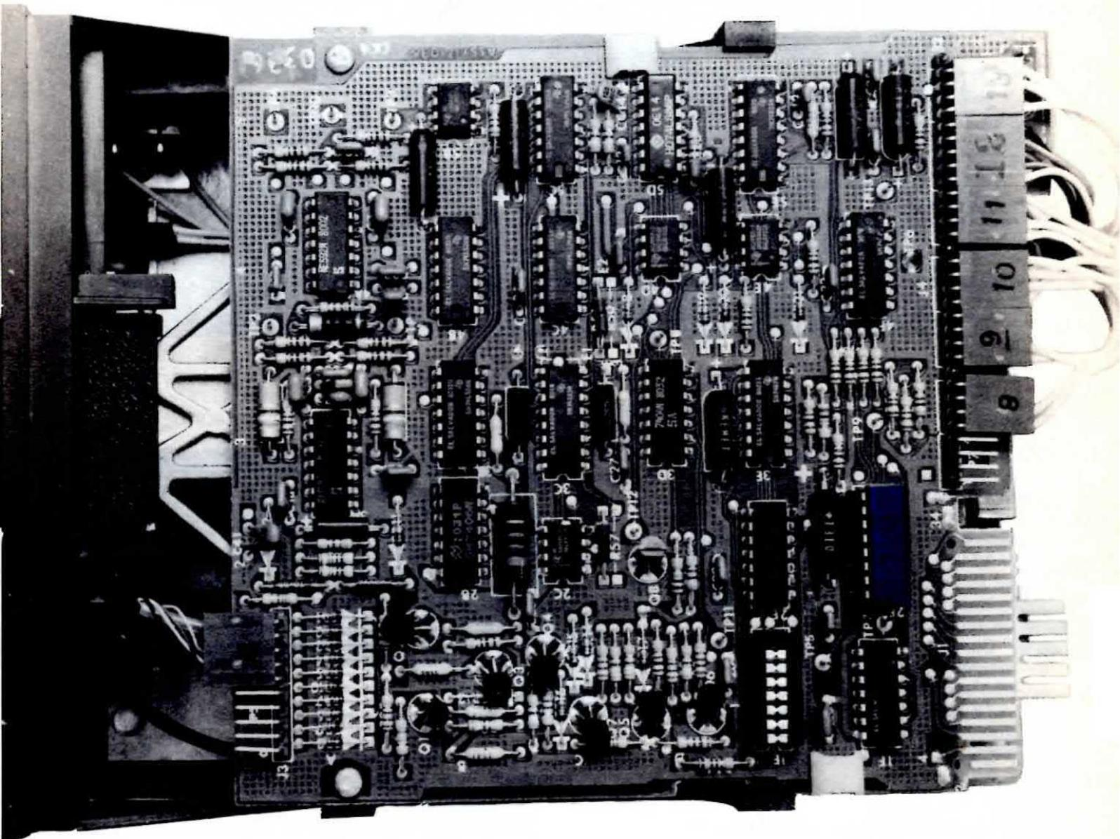
**Ogni drive per floppy-disk, oltre al motorino per la rotazione, a quello passo-passo per gli spostamenti della testina e alla testina stessa, dispone di una scheda elettronica sulla quale sono presenti diversi integrati, resistenze e transistor.**
