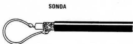
Fig. 8 Per prelevare il segnale di AF da un qualsiasi trasmettitore applicheremo all'estremità di un cavetto coassiale da 52 una semplice spira in rame. L'estremità opposta del cavo coassiale la collegheremo all'entrata del trasformatore T1.
