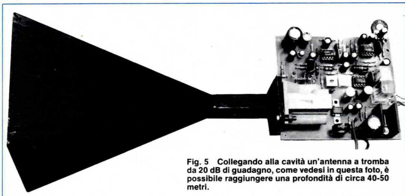
Fig. 5 Collegando alla cavità un'antenna a tromba da 20 dB di guadagno, come vedesi in questa foto, è possibile raggiungere una profondità di circa 40-50 metri.
