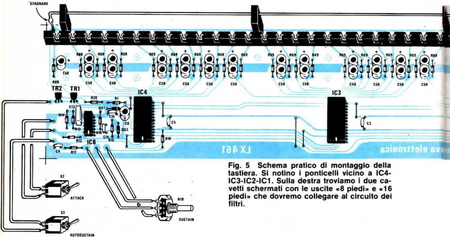
Fig. 5 Schema pratico di montaggio della tastiera. Si notino i ponticelli vicino a IC4-IC3-IC2-IC1. Sulla destra troviamo i due cavetti schermati con le uscite «8 piedi» e «16 piedi» che dovremo collegare al circuito dei filtri.
