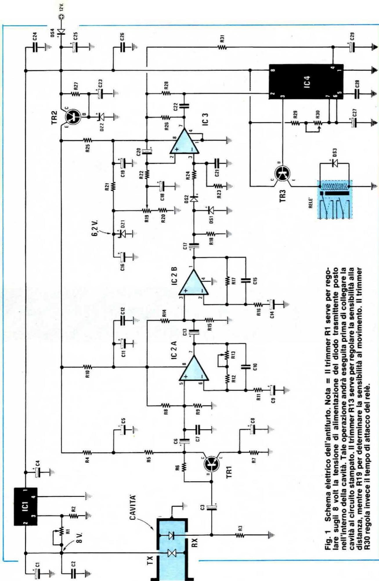
Fig. 1 Schema elettrico dell'antifurto. Nota = Il trimmer R1 serve per regolare sugli 8 volt la tensione di alimentazione del diodo trasmittente posto nell'interno della cavità. Tale operazione andrà eseguita prima di collegare la cavità al circuito stampato. Il trimmer R13 serve per regolare la sensibilità alla distanza, mentre R19 per determinare la sensibilità al movimento. Il trimmer R30 regola invece il tempo di attacco del relè.
