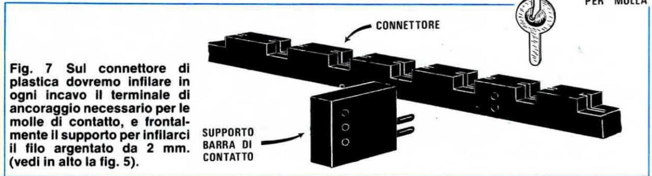
Fig. 7 Sul connettore di plastica dovremo infilare in ogni incavo il terminale di ancoraggio necessario per le molle di contatto, e frontalmente il supporto per infilarci il filo argentato da 2 mm. (vedi in alto la fig. 5).
