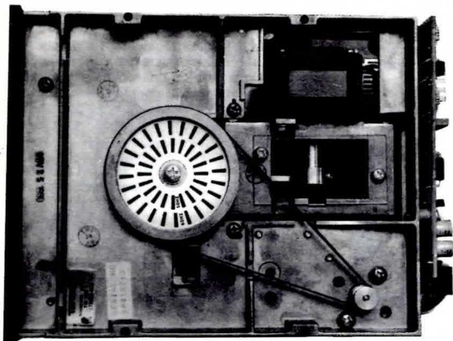
**Fig. 8** Collocando lo stroboscopio sotto una lampada alimentata dalla rete a 50 Hz e facendo ruotare il disco, quando questo è in movimento le linee interne debbono apparire immobili: se così non fosse occorrerà ruotare in un senso o nell'altro il trimmer che abbiamo posto in evidenza in fig. 1 fino a raggiungere lo scopo.
