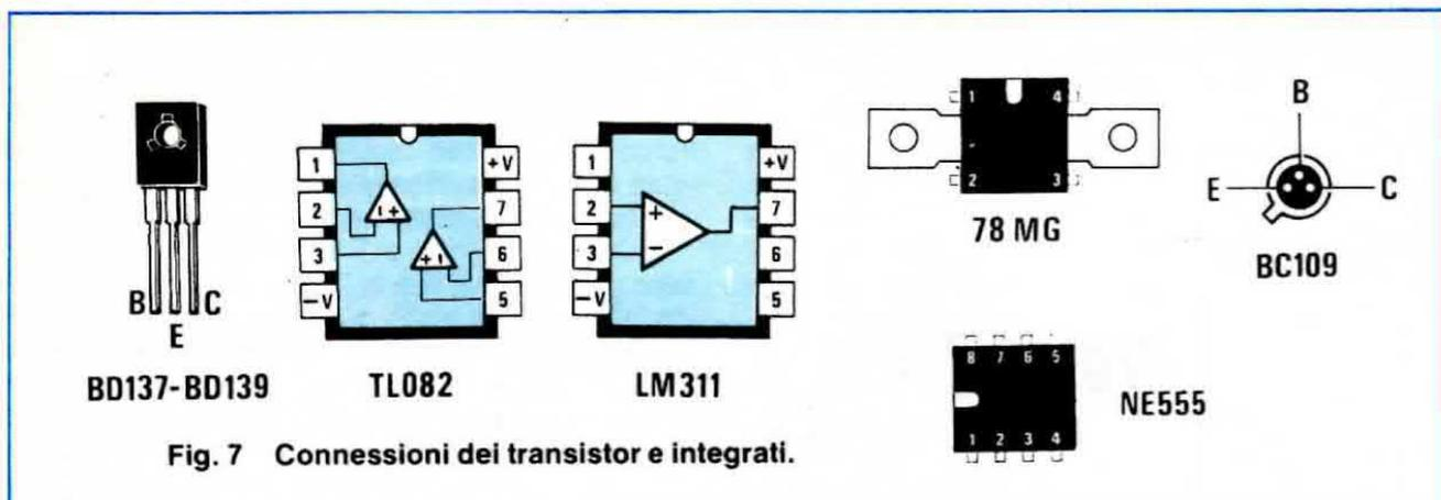
Fig. 7 Connessioni dei transistor e integrati.
