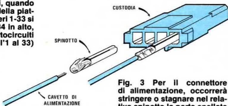
**Fig. 3** Per il connettore di alimentazione, occorrerà stringere o stagnare nel relativo spinotto la parte spellata del filo di rame, poi infilarlo tutto dentro la custodia in plastica.
