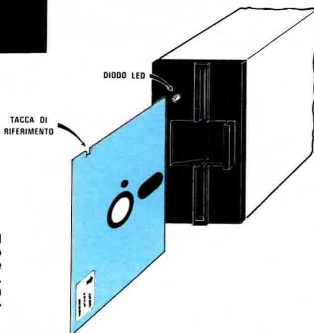
**Fig. 12** Il floppy andrà inserito entro il drive tenendo la tacca di riferimento rivolta dalla parte in cui sul pannello è presente il diodo led (vedi disegno). Inserite sempre il disco fino in fondo in modo che il foro centrale possa coincidere con il perno del motorino.
