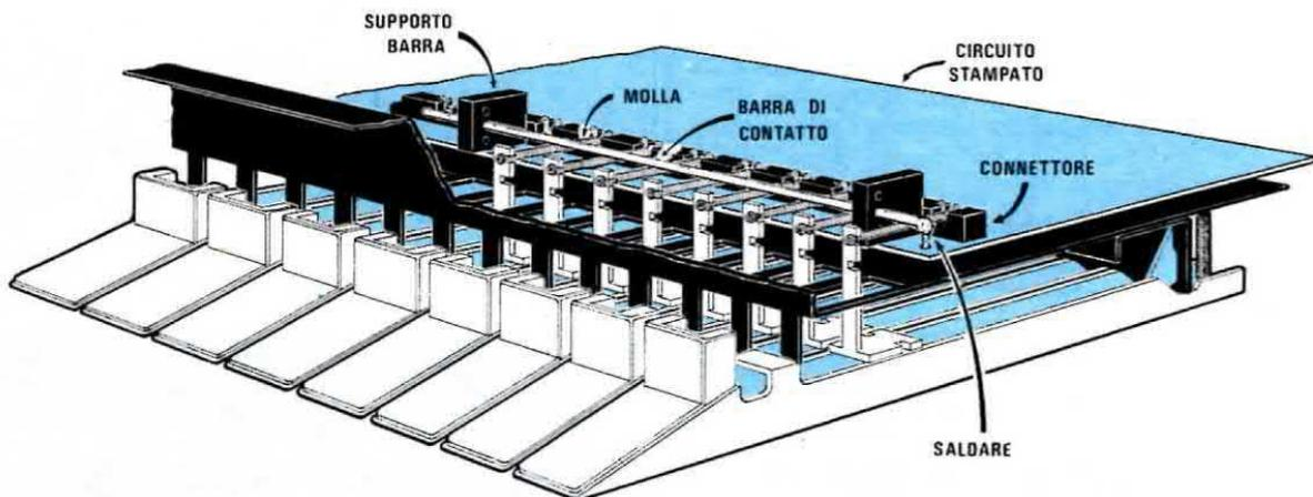
**Fig. 10** La barra di contatto, cioè il filo argentato da 2 mm che infileremo entro i fori dei supporti in plastica, dovrà essere stagnato ai due estremi sui due terminali presenti sul circuito stampato della tastiera (vedi anche fig. 5). Controllate inserendo questa barra che le mollette di contatto risultino da essa distanziate di pochi millimetri e solo pigiando il tasto effettuino un ottimo contatto con tale barra.
