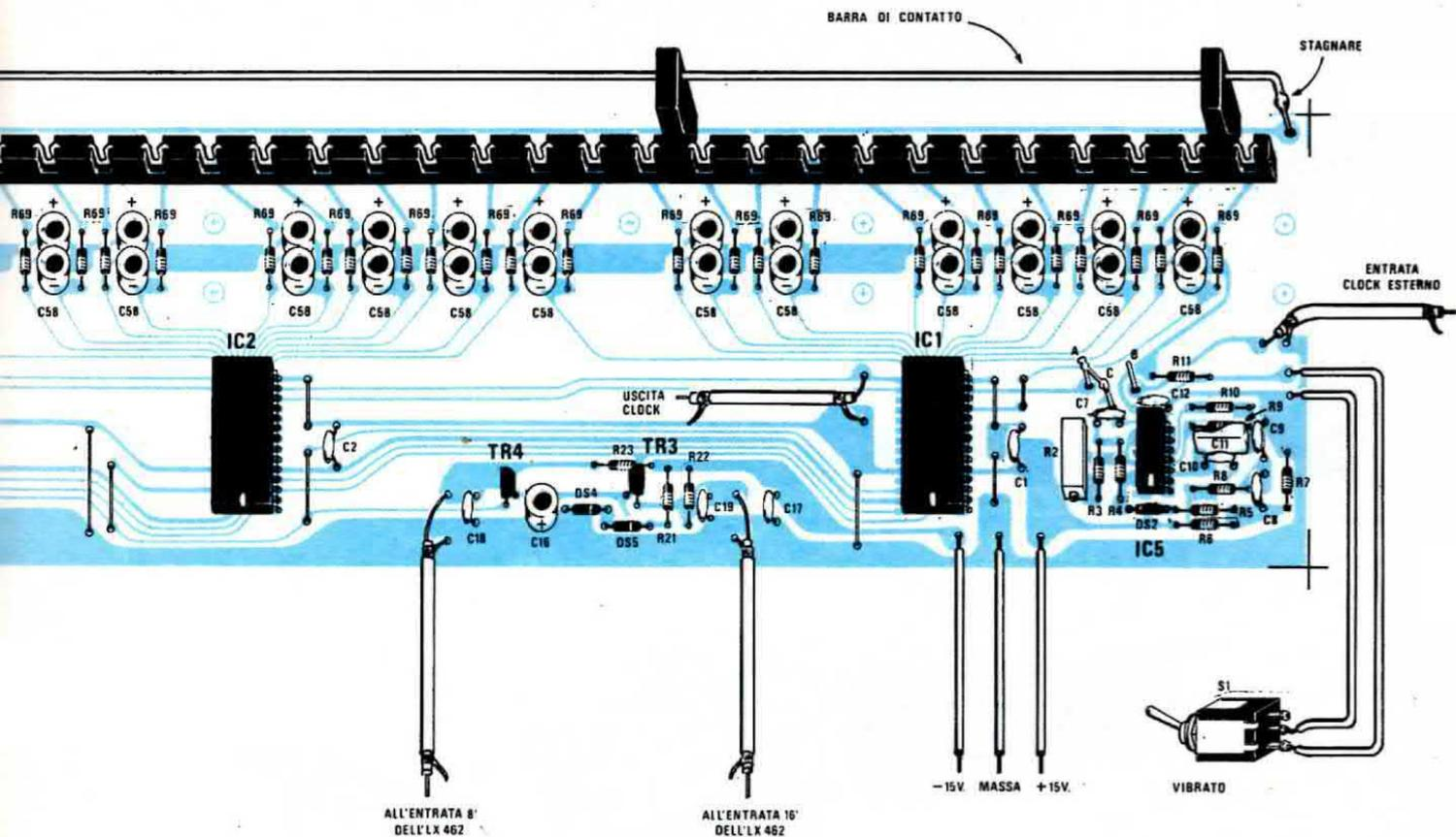
Fig. 8 In questa foto si può vedere, anche se notevolmente ridotta, la parte destra della nostra tastiera. Noteremo l'integrato IC5, poi il trimmer multigiri R2 necessario per la taratura della frequenza dell'oscillatore, infine l'integrato IC1 e i due transistor TR3-TR4. Facciamo presente al lettore che sul circuito stampato è riportato un disegno serigrafico dei componenti che agevolerà notevolmente la realizzazione.
