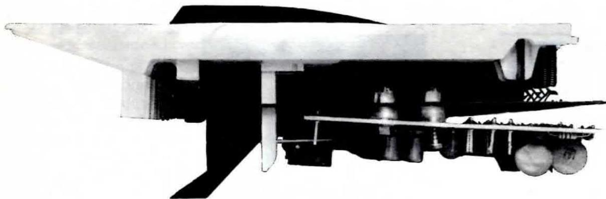
**Fig. 13** Il circuito stampato LX. 461 (quello visibile in fig. 5) dovrà essere fissato sul piano metallico di supporto della tastiera. Per fare questo sarà necessario interporre dei distanziatori di plastica utili per tenere la parte sottostante del circuito stampato isolata dal metallo. Per evitare cortocircuiti controllate che non esistano terminali di componenti troppo lunghi tanto da toccare la piastra metallica.
