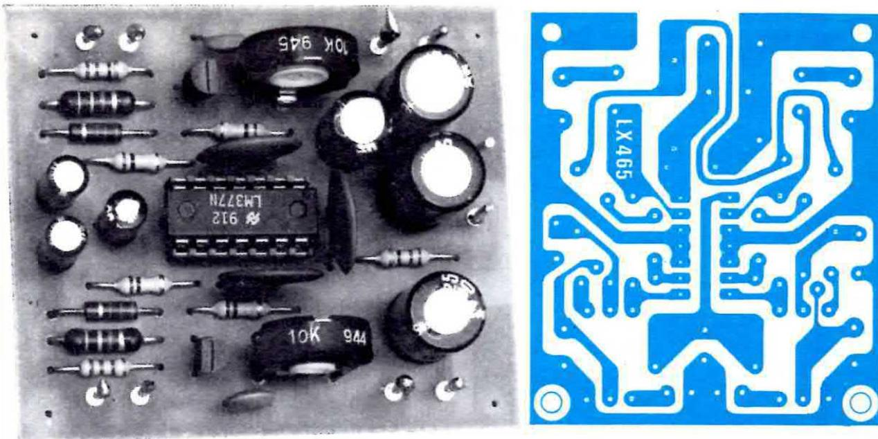
**Fig. 3** Foto ingrandita dell'interfono per moto come si presenta a montaggio ultimato. Si notino ai quattro lati i terminali necessari per collegare i cavetti che si congiungeranno ai microfoni e agli auricolari. Sulla destra il disegno a grandezza naturale del circuito stampato siglato LX.465.
