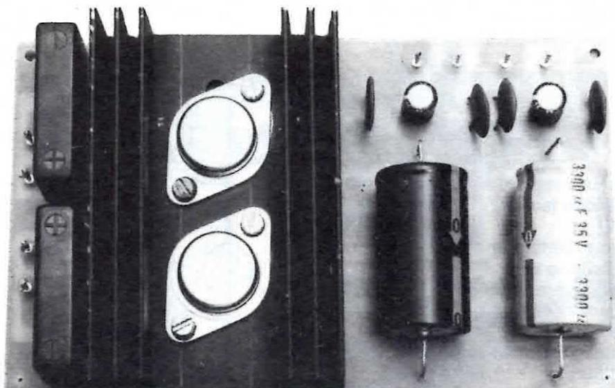
Foto notevolmente ridotta del prototipo di questo alimentatore da noi realizzato per i necessari collaudi: si noti l'aletta di raffreddamento su cui risultano fissati i due integrati stabilizzatori.
