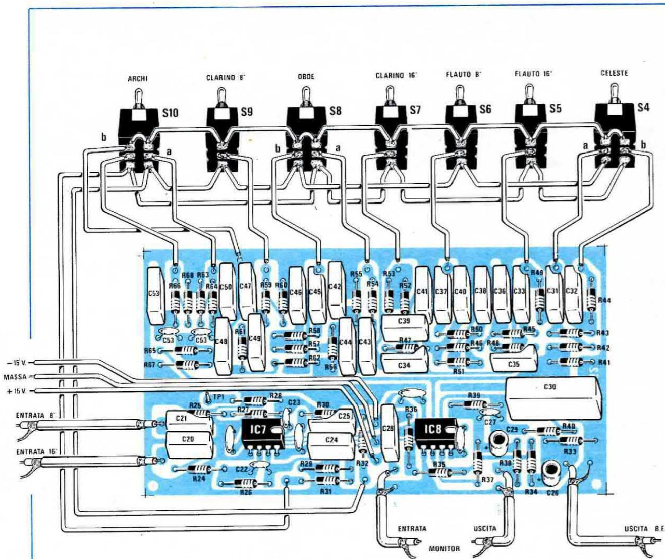
**Fig. 14** Schema pratico di montaggio del circuito degli effetti LX.462. L'unico problema che si può presentare è quello dei collegamenti elettrici con gli interruttori tuttavia riteniamo che con un po' di attenzione e controllando sia lo schema elettrico che quello pratico, tale difficoltà risulti facilmente risolta. Per il collegamento alla piastra LX.461 e per l'uscita del segnale di BF, utilizzare del cavetto schermato.
