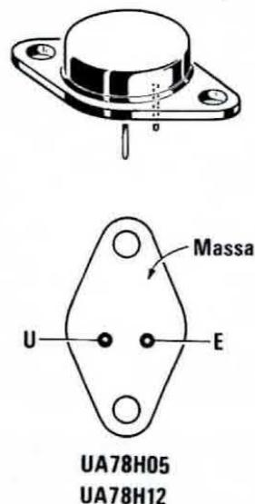
**Fig. 2** Connessioni (viste da sotto) dei due integrati stabilizzatori impiegati in questo progetto. L'involucro esterno è collegato alla massa quindi non esiste il pericolo di cortocircuiti.
