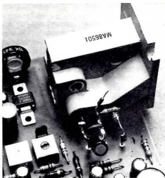
**Fig. 4** In questa foto si può vedere il diodo di protezione tranciato dal terminale RX e i condensatori C1 e C2 stagnati direttamente tra il terminale TX e quello di massa (terminale centrale). **NOTA** = la cavità potrà essere fissata sul circuito stampato con qualche goccia di collante cementatutto.
