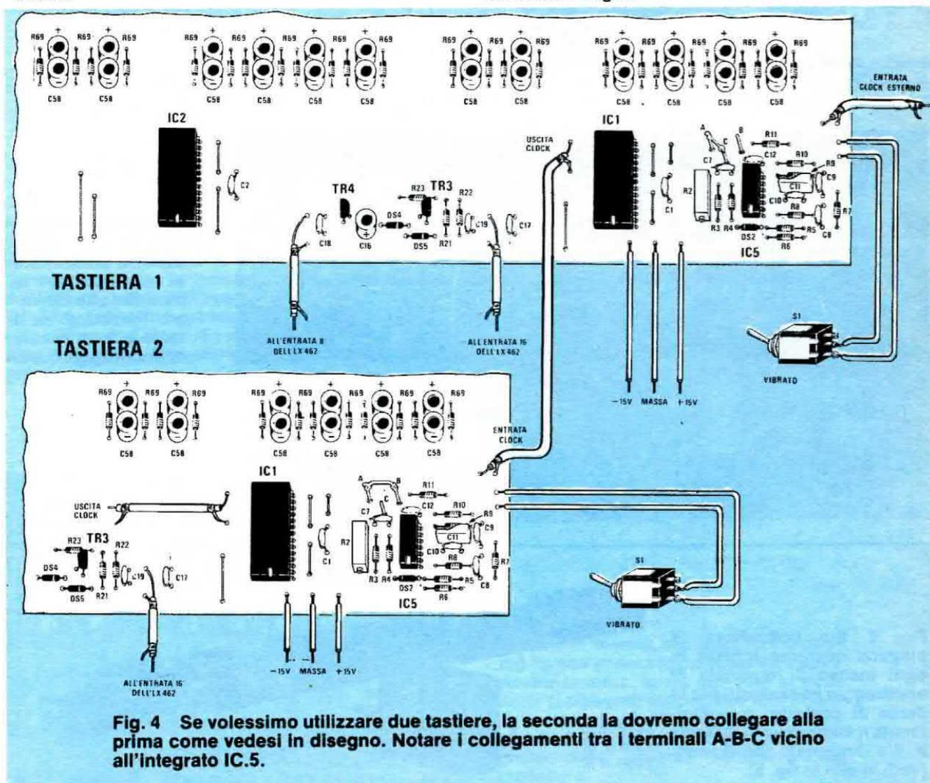
**Fig. 4** Se volessimo utilizzare due tastiere, la seconda la dovremo collegare alla prima come vedesi in disegno. Notare i collegamenti tra i terminali A-B-C vicino all'integrato IC.5.
