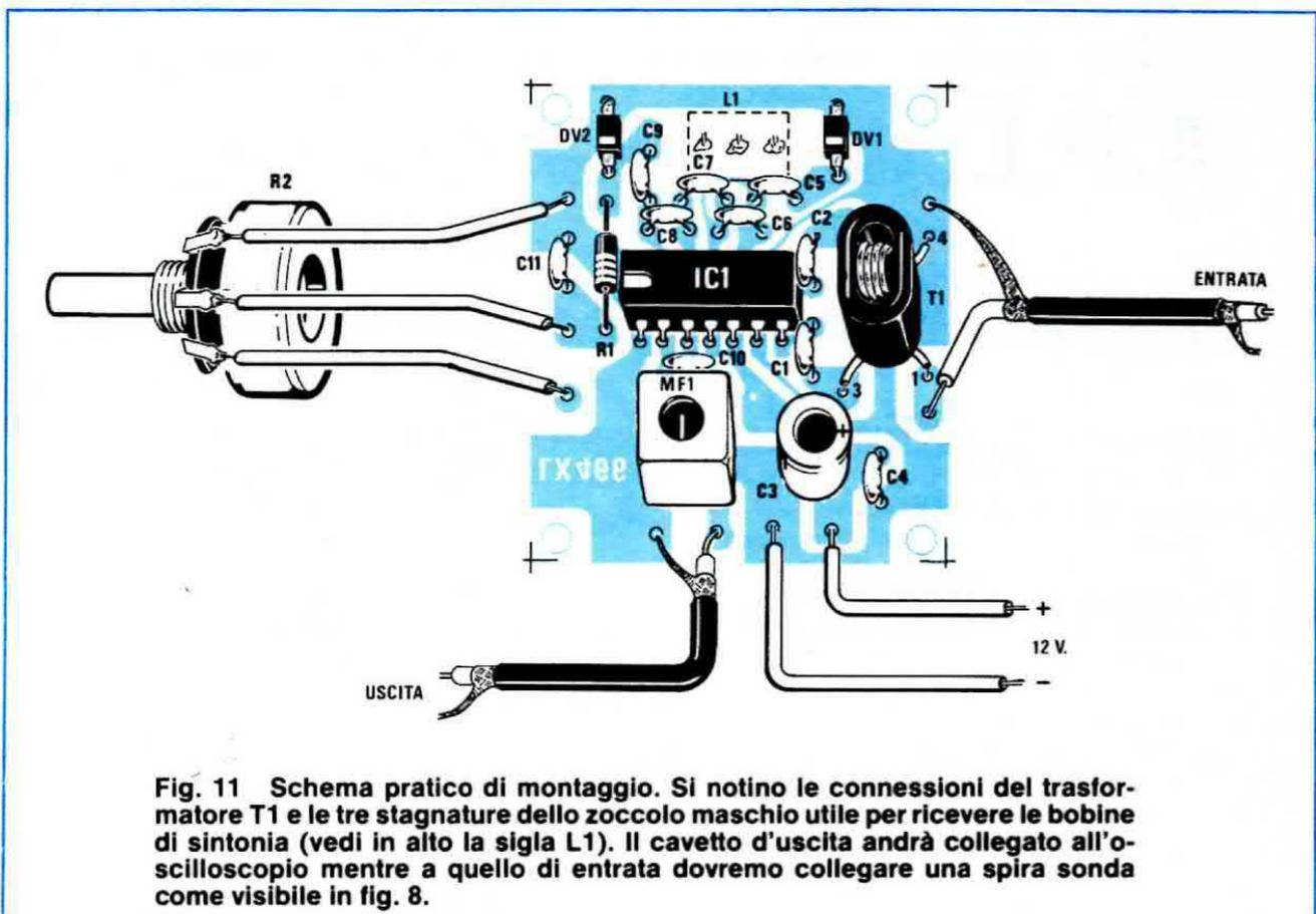
Fig. 11 Schema pratico di montaggio. Si notino le connessioni del trasformatore T1 e le tre stagnature dello zoccolo maschio utile per ricevere le bobine di sintonia (vedi in alto la sigla L1). Il cavetto d'uscita andrà collegato all'oscilloscopio mentre a quello di entrata dovremo collegare una spira sonda come visibile in fig. 8.
