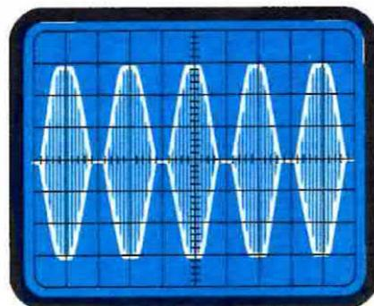
Fig. 3 Quando si sovrasmodula un segnale di AF, gli estremi superiori ed inferiori di detto segnale risultano squadrati ed al centro la separazione tra le due semionde è molto netta. Tale condizione provoca un'elevata distorsione sul segnale di BF e per eliminarla è necessario abbassare il volume.
