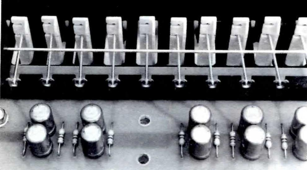
Fig. 6 Si noterà in questo particolare la barra orizzontale di contatto e le mollette che dovremo innestare tra il tasto e il terminale di ancoraggio (vedi sotto).
