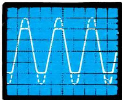
**Fig. 11** Se il segnale applicato all'ingresso risultasse di ampiezza troppo elevata, tanto che amplificandola dovesse superare il limite indicato precedentemente nella fig. 10 la nostra onda sinusoidale verrebbe «tosata» sia nella parte superiore della semionda positiva che in quella inferiore della semionda negativa ricavando così un'onda quadra.
