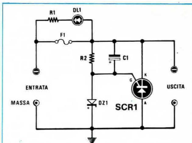
**Fig. 2** Schema per la tensione negativa dei 12 volt.
