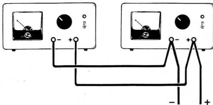
**Fig. 9** Realizzando due alimentatori, è possibile collegandoli in parallelo, raddoppiare la corrente in uscita. Per evitare cortocircuiti nell'eventualità i due alimentatori venissero regolati inavvertitamente su due tensioni diverse, si consiglia di applicare in serie sulle due uscite positive un diodo raddrizzatore di potenza (50 volt 10 amper).
