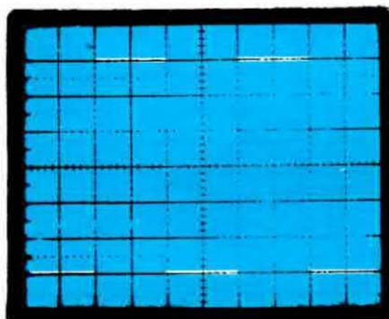
**Fig. 3** Le due frequenze, 1250 Hz e 78 Hz dispongono di un'ampiezza massima di 10 volt, più precisamente, disporremo di una semionda positiva di 5 volt rispetto alla massa, ed una corrispondente semionda negativa di 5 volt sempre rispetto alla massa. La semionda positiva la sfrutteremo per pilotare i transistor NPN (vedi TR3 e TR5) mentre quella negativa per pilotare i transistor PNP (vedi TR4 e TR6)
