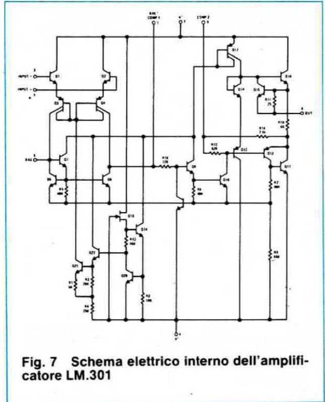
5) È possibile accoppiarlo a qualsiasi altro circuito senza ottenere attenuazioni sull'ampiezza del segnale in quanto l'impedenza d'uscita è bassissima.
