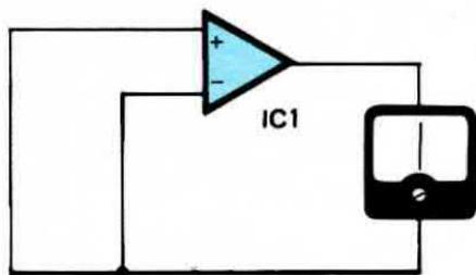
**Fig. 26** In teoria, collegando a massa i due ingressi in quello di uscita dovremmo rilevare tensione zero, in pratica invece per inevitabili squilibri interni potrebbe risultare presente una tensione positiva o negativa di qualche millivolt che entrando sull'ingresso dello stadio successivo verrebbe amplificata. Questa tensione la si può eliminare utilizzando i due terminali di offset.
