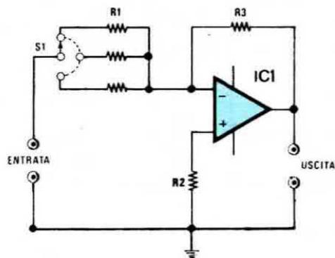
**Fig. 23** Contrariamente alla fig. 22 si potrebbe tenere invece fisso il valore di  $R3$  e modificare tramite un commutatore il valore ohmmico della resistenza  $R1$  applicata sull'ingresso. In questo secondo caso noi modificheremo l'impedenza in ingresso, in quanto questa risulta sempre equivalente al valore di  $R1$ .
