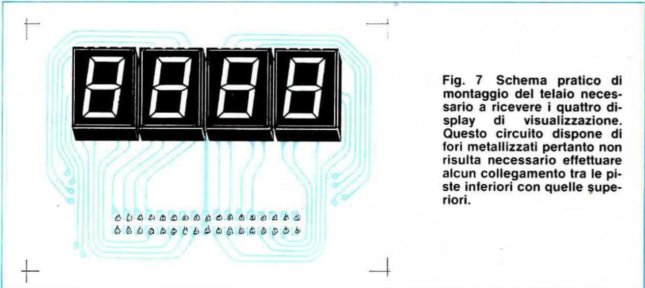
**Fig. 7** Schema pratico di montaggio del telaio necessario a ricevere i quattro display di visualizzazione. Questo circuito dispone di fori metallizzati pertanto non risulta necessario effettuare alcun collegamento tra le piste inferiori con quelle superiori.
