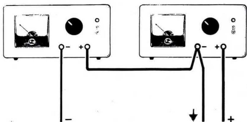
**Fig. 11** Disponendo di due alimentatori, e collegandoli come vedesi in disegno potremo ottenere un valido alimentatore duale dal quale ricavare una tensione minima di 4,5 + 4,5 volt fino ad un massimo di 25 + 25 volt. Il terminale di «massa» lo preleveremo dai due morsetti + e - che congiungono i due alimentatori.
