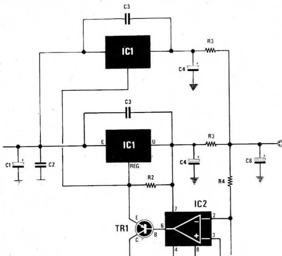
**Fig. 8** Per raddoppiare la corrente in uscita portandola da 5 amper a 10 amper sarà sufficiente collocare in parallelo al nostro circuito un altro LM.338K. Per evitare autooscillazione dovremo collegare un ulteriore condensatore C3 tra il terminale E-U dell'integrato più un condensatore elettrolitico C4 da 47 mF. 40-50 volt lavoro e una nuova R3.
