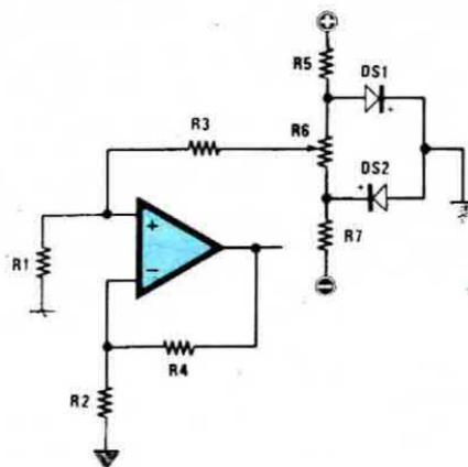
**Fig. 33** In questi casi la correzione dell'offset la si può facilmente ottenere con un semplice artificio, cioè collegare come vedesi in figura i due terminali di un trimmer al positivo e al negativo di alimentazione e collegando l'ingresso non invertente al cursore di tale trimmer con una resistenza di elevato valore ohmmico come spiegato nell'articolo.
