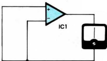
**Fig. 15** Collegando a massa i due ingressi ed applicando sull'uscita un voltmetro con lancetta al centro in modo da poter rilevare quando sull'uscita la tensione diventa negativa oppure positiva potremo notare che la lancetta rimane immobile, e questo per indicare che quando i due ingressi risultano ad identico potenziale in uscita risulta presente tensione «zero».
