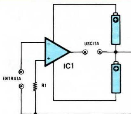
Fig. 12 Per alimentazione duale si intende una tensione positiva rispetto alla massa, ed una negativa sempre rispetto alla massa. Se alimentassimo un'operazionale con delle pile ne occorrebbero due disposte come vedesi in figura. La congiunzione tra le due pile corrisponde al filo di massa, sulla quale faranno capo i due ingressi invertente e non invertente ed anche il terminale d'uscita.
