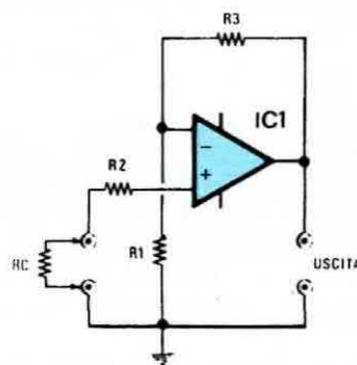
**Fig. 25** Pertanto quando l'impedenza dello stadio che precede il nostro amplificatore è elevata risulta consigliabile utilizzare l'ingresso non invertente, in quanto a differenza dello schema di fig. 24 non si modifica il guadagno dell'amplificatore.
