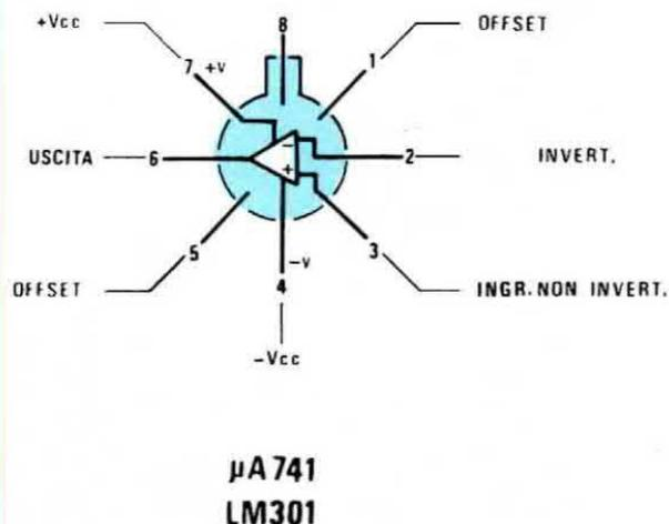
**Fig. 2** Disposizione dei terminali visti da sotto di un'amplificatore operazionale in contenitore metallico. Ricordatevi che i terminali di alimentazione + e - si intendono sempre per tensione duale.
