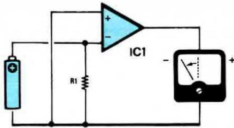
**Fig. 17** Se invece applicassimo una tensione positiva sull'ingresso invertente, vedremo la lancetta dello strumento spostarsi verso sinistra, e questo per indicarci che la polarità in uscita è di segno opposto a quello applicato sull'ingresso. Invertendo la pila, la lancetta dello strumento si sposterebbe invece verso destra, cioè in uscita avremo tensione positiva.
