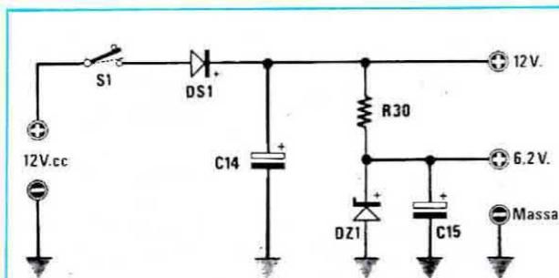
**Fig. 2** Schema elettrico dell'alimentatore
