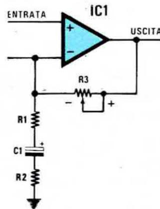
**Fig. 2** Lasciando fissa la resistenza R2 noi potremo ugualmente modificare il guadagno di un amplificatore operazionale inserendo in sostituzione della resistenza R3 un potenziometro. In questo caso l'amplificazione risulterà minima quando la R3 risulterà cortocircuitata.
