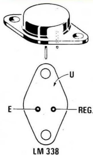
**Fig. 2** (in basso) Esternamente l'integrato LM.338K si presenta come un normale transistor di potenza e come tale dispone di soli tre terminali
