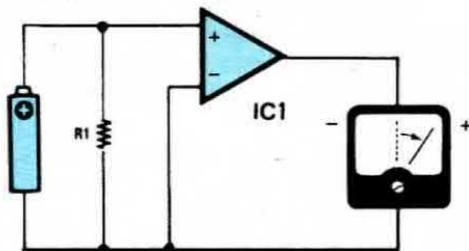
**Fig. 16** Se ora sull'ingresso non invertente + applicassimo una tensione positiva vedremo la lancetta del nostro strumento spostarsi verso destra, indicandoci che in uscita risulta presente una tensione di uguale segno. Se invertissimo la pila in modo da applicare all'ingresso una tensione negativa la lancetta si sposterebbe verso sinistra.
