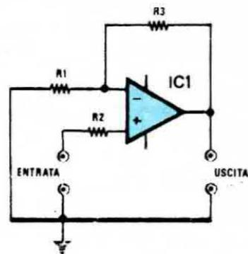
Fig. 21 Il guadagno non viene modificato nemmeno se entriamo sull'ingresso non invertente anziché su quello invertente come indicato in fig. 20, in questo caso la R1 la dovremo collegare a massa. Il valore della resistenza R2 applicata in serie al terminale non invertente serve solo ad aumentare l'impedenza d'ingresso e non influisce nel calcolo del guadagno. Per ingressi ad alta impedenza è più consigliabile questo secondo circuito.
