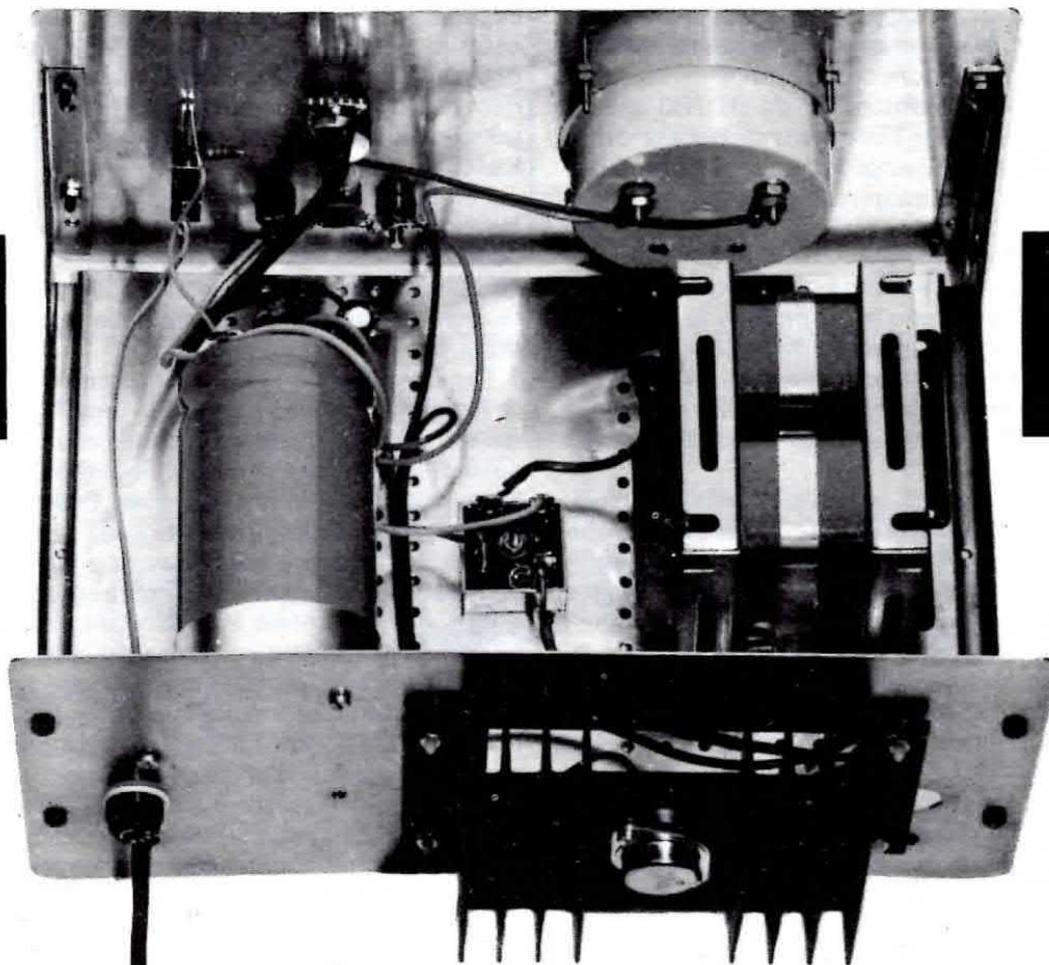
vedesi in fig. 9, dopo aver regolato i due potenziometri sullo stesso identico valore, potrà ricavare il doppio di corrente, cioè disporre di un alimentatore in grado di erogare un massimo di 10-12 ampère su qualsiasi tensione compresa fra un minimo di 4,5 volt ed un massimo di 25 volt.
