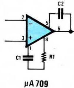
**Fig. 19** L'amplificatore operazionale uA.709 che a differenza di ogni altro dispone di tre terminali per la compensazione in frequenza, lo dovremo utilizzare come vedesi in figura. Cioè sul terminale 5 con un piccolo condensatore gli applicheremo parte del segnale disponibile sul terminale d'uscita, mentre sugli altri due terminali 1-8 gli applicheremo una resistenza con in serie un condensatore i cui valori si calcoleranno in fase di progetto.
