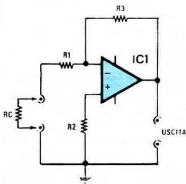
**Fig. 24** Utilizzando l'ingresso invertente dovremo sempre considerare nel calcolo del guadagno anche l'impedenza dello stadio che lo precede in quanto se tale impedenza dovesse risultare di valore troppo elevato questo potrebbe modificare anche notevolmente il guadagno di tale stadio.
