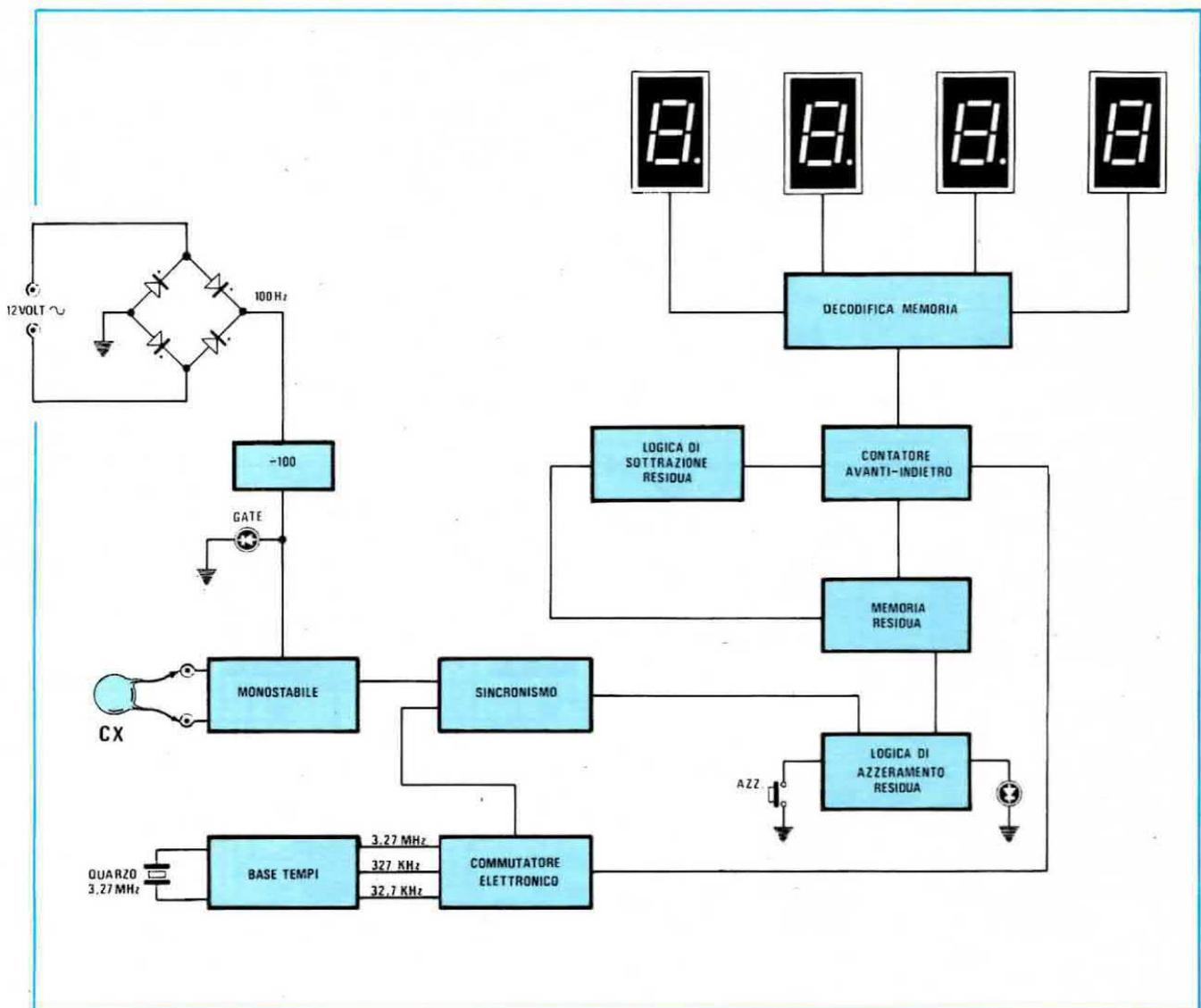
**Fig. 1** Per ottenere una elevata precisione di lettura sulle capacità minime (il capacimetro indica anche i decimali di picofarad) si è dovuto inserire un circuito di memoria che automaticamente azzerasse la capacità residua dei cavetti esterni e del relativo circuito stampato. Un contatore avanti-indietro sottrarrà su ogni portata la capacità residua fino ad un massimo di 100 picofarad.
