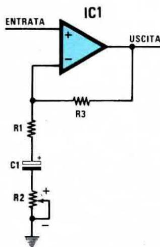
**Fig. 1** Per variare manualmente il guadagno di un'amplificatore operazionale potremo applicare inn serie a C1 un potenziometro (vedi R2). Quando la resistenza di questo risulterà massima, l'amplificazione sarà minima, cortocircuitando la resistenza, l'amplificazione risulterà massima.
