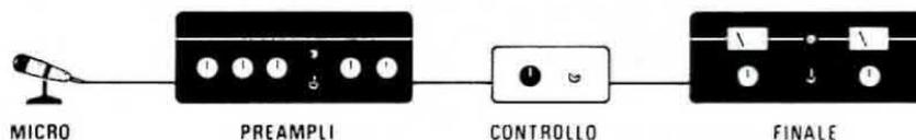
**Fig. 9** Il controllo automatico di volume è sempre consigliabile applicarlo dopo un preamplificatore o un mixer, anche se applicando il microfono direttamente sull'entrata questo funzionerà ugualmente bene.
