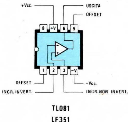
**Fig. 1** Disposizione dei terminali visti da sopra di un'amplificatore operazionale in un contenitore mini-dip plastico. Si noti i due piedini 1-5 da utilizzare per l'offset.
