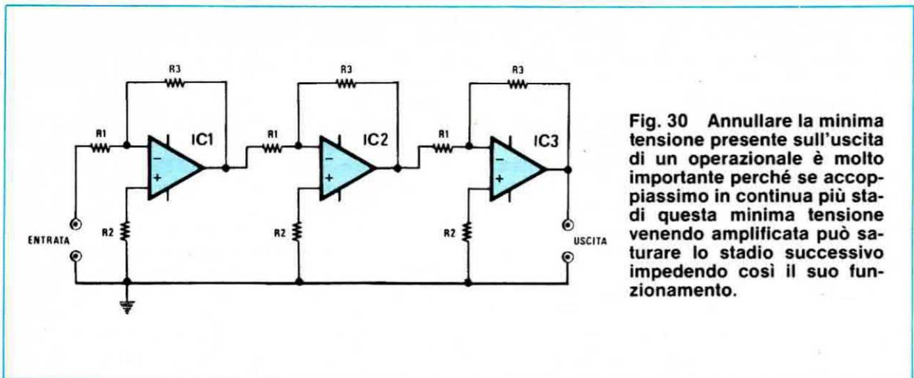
**Fig. 30** Annullare la minima tensione presente sull'uscita di un operazionale è molto importante perché se accoppiassimo in continua più stadi di questa minima tensione venendo amplificata può saturare lo stadio successivo impedendo così il suo funzionamento.
