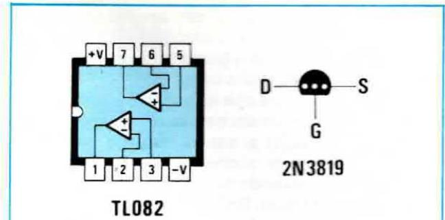
**Fig. 7** Connessioni dei terminali dell'integrato TL.082 visto da sopra e del fet 2N3819 visto invece da sotto. Si può notare nel disegno come i terminali del fet risultano in linea, e questo è importante in quanto altri 2N3819 come vedesi nel disegno qui sotto riportato hanno i terminali disposti in modo diverso.
