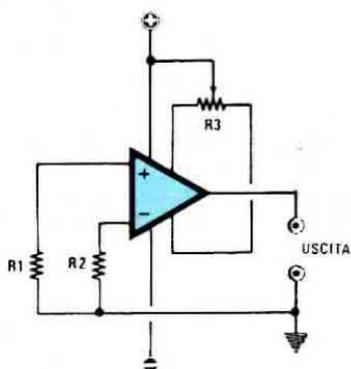
Fig. 28 Quando l'operazionale dispone di due terminali di offset su questi applicheremo i terminali estremi di un trimmer. Se nelle caratteristiche di tale operazionale risultasse precisato che l'offset è positivo il cursore di questo trimmer dovremmo collegarlo al «positivo» di alimentazione come riportato in questo schema elettrico.
