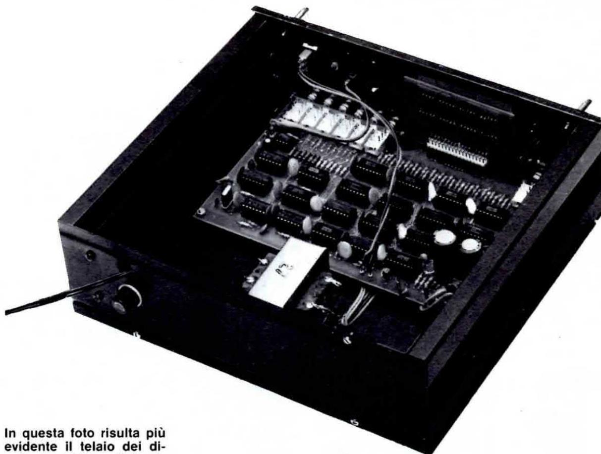
**In questa foto risulta più evidente il telaio dei display innestato sul circuito di base LX.486**
