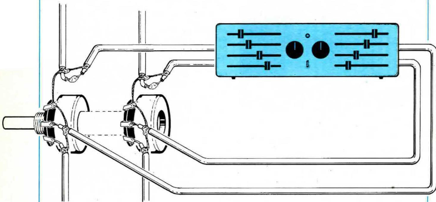
Fig. 8 Il cavetto che avrete dissaldato dal terminale centrale dei due potenziometri, lo dovete collegare al cavetto schermato che si collega all'ingresso dei due canali dell'equalizzatore. Le due uscite dell'equalizzatore, sempre utilizzando del cavetto schermato, le dovremo collegare al terminale centrale dei due potenziometri di volume della vostra radio come vedesi in questo disegno. Non dimenticate di collegare a massa la calza metallica dei due cavetti schermati.
