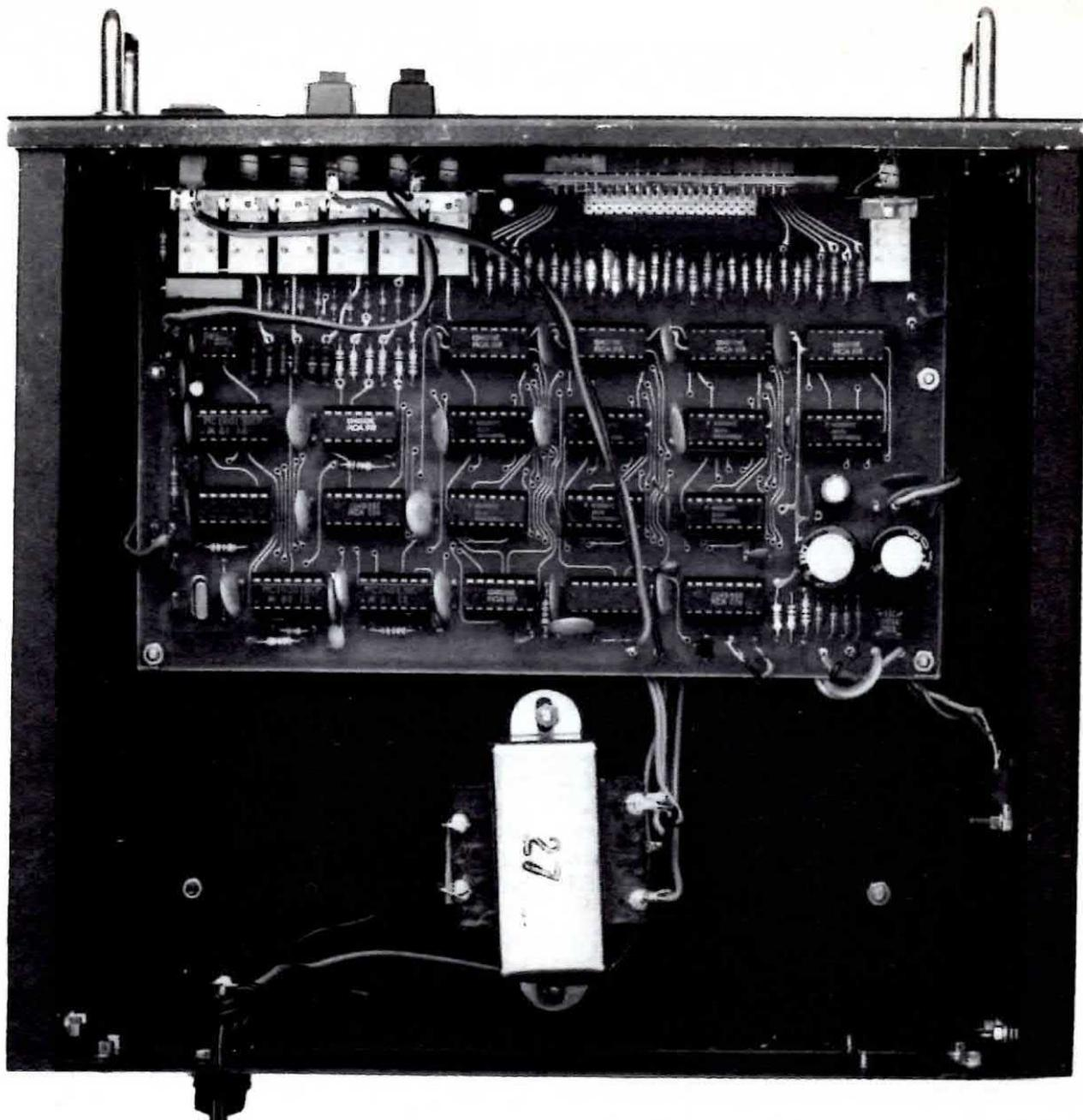
**Fig. 5** In questa foto possiamo vedere come risulta disposto nell'interno del mobile il circuito stampato del capacimetro ed il relativo trasformatore di alimentazione. Il telaio del display innestato nel connettore del circuito base appoggerà vicinissimo al plexiglass rosso incollato sulla finestra frontale di lettura. Si noti a destra l'integrato stabilizzatore IC22 fissato sul pannello laterale del mobile.
