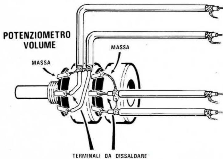
Fig. 7 Il segnale da applicare agli ingressi del nostro equalizzatore andranno prelevati dal cursore centrale della vostra radio o mangianastri. Se la vostra radio è «stereo» avrete, come vedesi in disegno, un doppio potenziometro e su questo il cavetto da dissaldare sarà quello stagnato al terminale centrale di ogni potenziometro.
