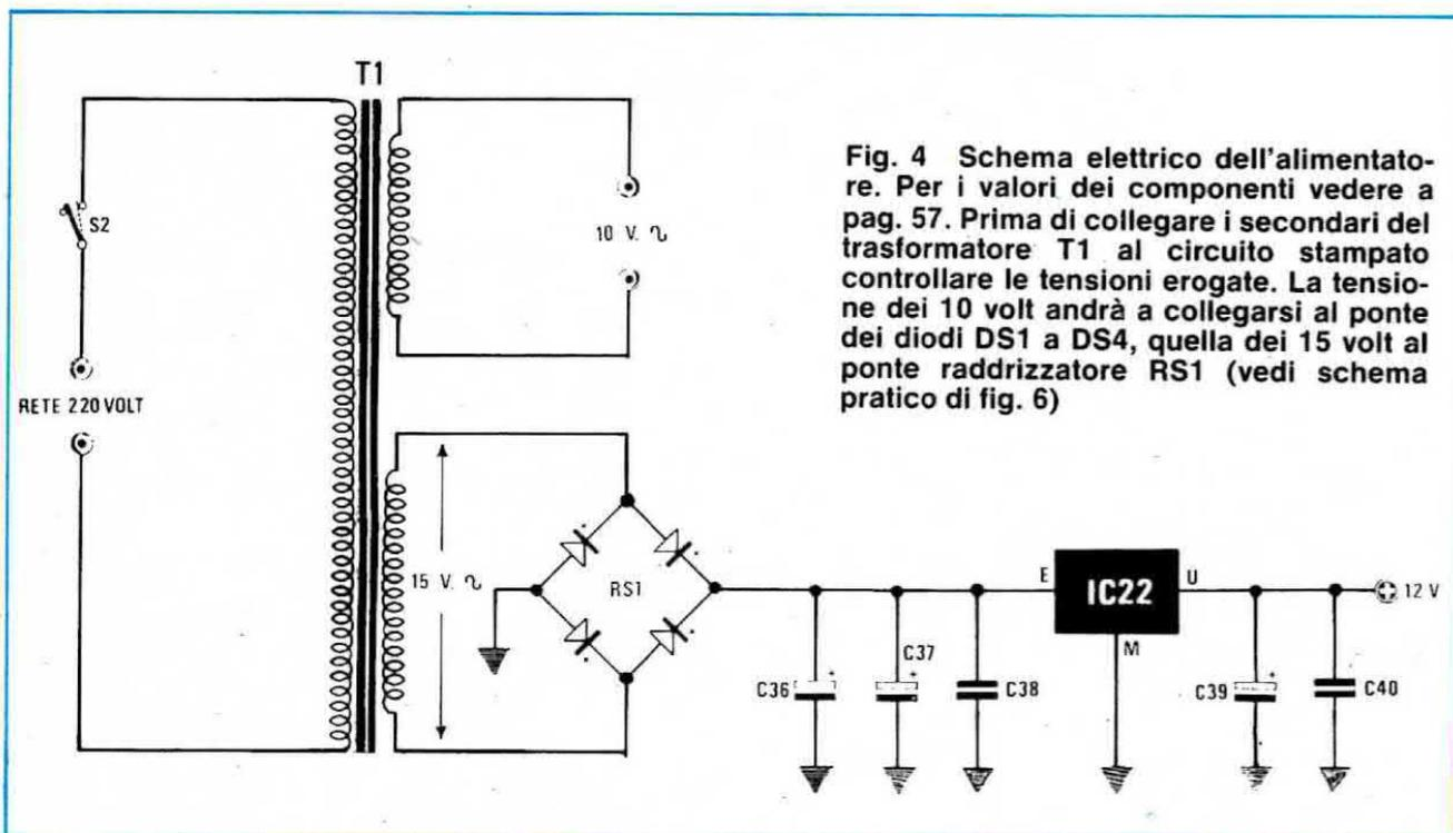
Fig. 4 Schema elettrico dell'alimentatore. Per i valori dei componenti vedere a pag. 57. Prima di collegare i secondari del trasformatore T1 al circuito stampato controllare le tensioni erogate. La tensione dei 10 volt andrà a collegarsi al ponte dei diodi DS1 a DS4, quella dei 15 volt al ponte raddrizzatore RS1 (vedi schema pratico di fig. 6)
