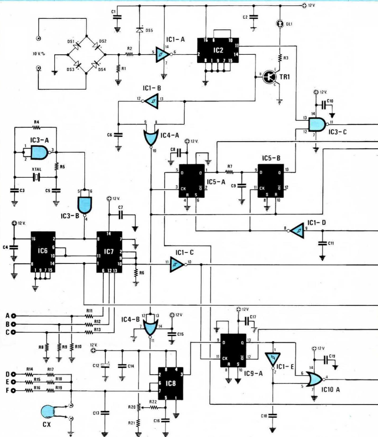
Fig. 2 Schema elettrico completo del capacimetro. Per i valori dei componenti vedere la pagina successiva. L'alimentatore è riportato in fig. 4 a pag. 58. NOTA = Le resistenze che alimentano i segmenti dei display da R23 a R52 (anche se non siglate nello schema elettrico per ragioni di spazio) sono tutte da 820 ohm ¼ di watt.
