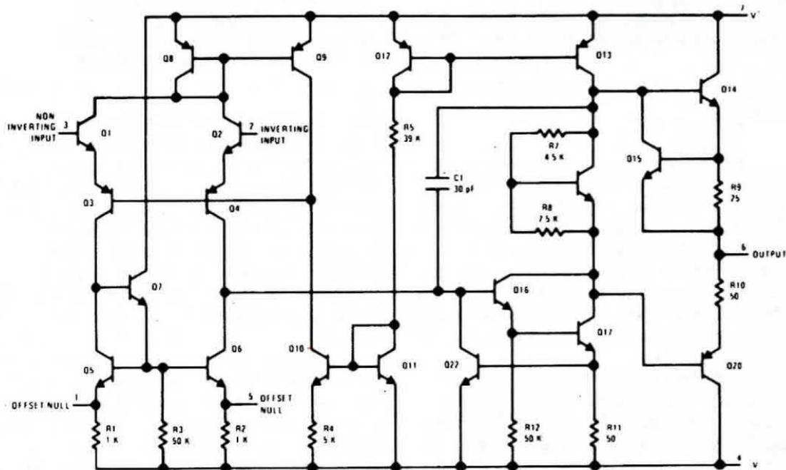
**Fig. 9** Schema elettrico interno dell'amplificatore operazionale uA.741
