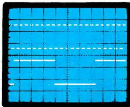
**Fig. 2** Sul piedino 3 dell'integrato IC2 preleveremo una frequenza di circa 1250 Hz mentre dal piedino 11 una frequenza di circa 78 Hz. Controllando con un oscilloscopio a doppia traccia i segnali presenti su questi due piedini, vedremo sullo schermo una figura simile a quella riportata in questa foto.
