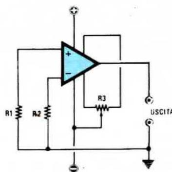
Fig. 29 Ad esempio l'integrato uA.741 e il TL.081 ha un offset «negativo» pertanto il cursore del trimmer verrà collegato alla tensione negativa di alimentazione come vedesi in figura. Se per errore lo collegassimo alla tensione positiva anziché annullare sull'uscita quei pochi millivolt presenti ne aumenteremo lo sbilanciamento.
