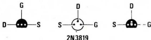
Fig. 3 Il fet 2N3819 lo possiamo trovare con tre differenti zoccolature, quello impiegato nel progetto ha i terminali in linea D-G-S (prima figura a sinistra).
