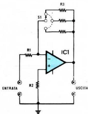
**Fig. 22** Sapendo che il guadagno viene determinato dal rapporto  $R3:R1$  per ottenere degli amplificatori a guadagno variabile si potrebbe realizzare uno schema come visibile in figura, cioè utilizzare un commutatore che inserisca tra il terminale d'uscita e quello invertente delle resistenze ( $R3$ ) di valore ohmmico diverso.
