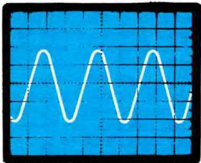
**Fig. 10** La massima ampiezza del segnale prelevabile in uscita da un'amplificatore operazionale risulterà sempre minore di 4 volt rispetto alla massima tensione di alimentazione. Alimentando un amplificatore operazionale con una tensione duale di 15 + 15 volt la massima ampiezza del segnale in uscita non potrà mai superare i  $30 - 4 = 26$  volt.
