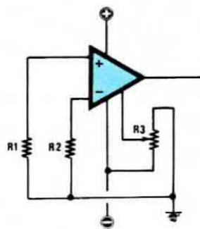
**Fig. 27** Negli amplificatori operazionali che dispongono di un solo terminale di offset, anziché due come nella maggioranza dei casi, questo terminale dovremo collegarlo al cursore di un trimmer il cui estremo risulta collegato a massa e l'altro alla tensione negativa di alimentazione. Regolando tale trimmer si potrà annullare questa tensione sull'uscita.
