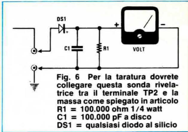
**Fig. 6** Per la taratura dovrete collegare questa sonda rivelatrice tra il terminale TP2 e la massa come spiegato in articolo
