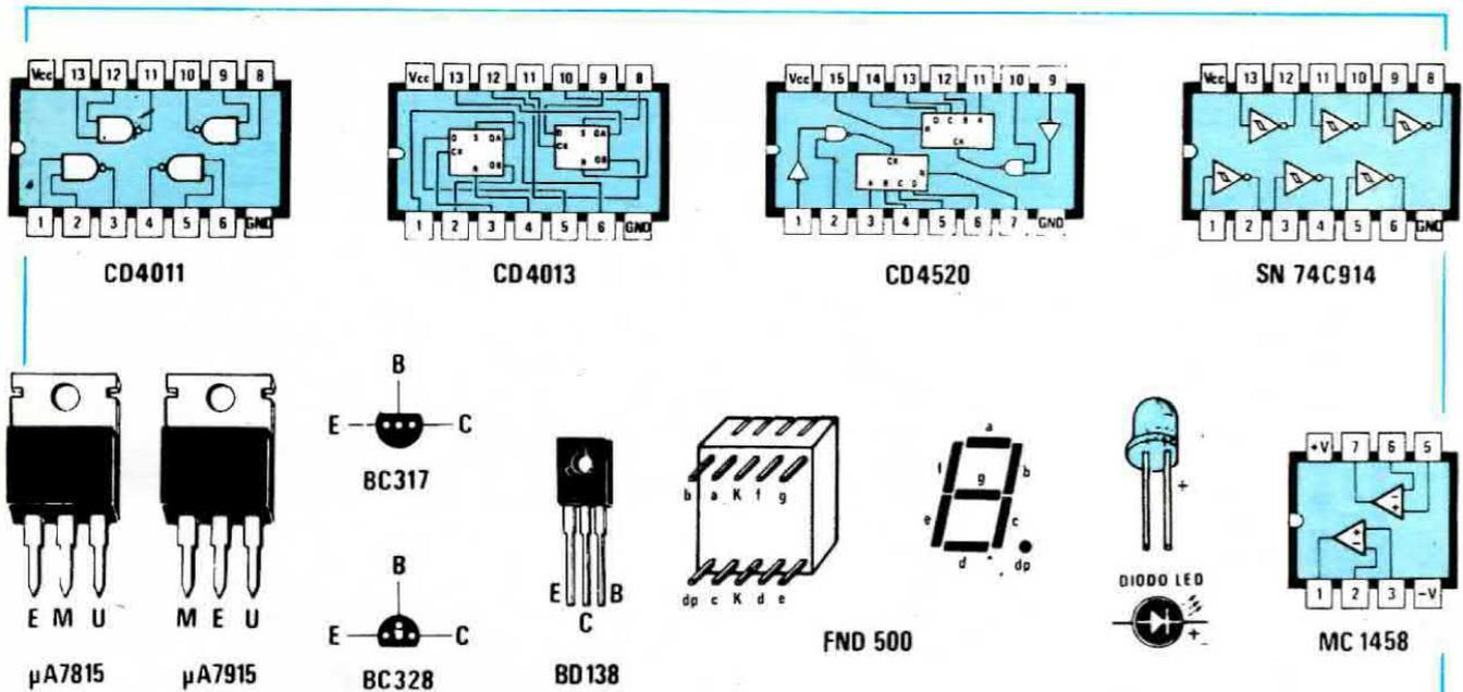
**Fig. 7** Qui sopra abbiamo riportato tutte le connessioni degli integrati C/MOS richiesti per questa realizzazione visti da sopra, e quelli dei transistor BC.317 e BC.328 visti invece da sotto. Attenzione a non invertire sul circuito stampato i due integrati stabilizzatori  $\mu$ A.7815 (IC6 che fornisce tensione positiva) con il  $\mu$ A.7915 (IC7 che invece fornisce tensione negativa) Per i diodi led ricordatevi che il terminale più lungo è sempre quello positivo.
