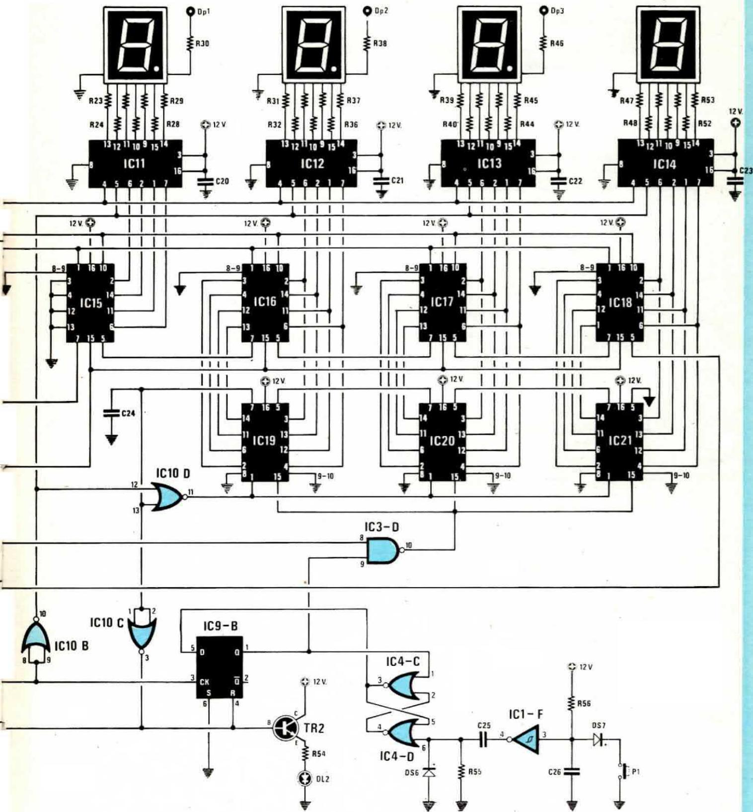
fettiva capacità del condensatore, verranno regolarmente conteggiati in avanti cosicchè sui display vedremo comparire il solo numero 2 (cioè 2 pF) corrispondente appunto alla capacità reale del condensatore sotto prova.
