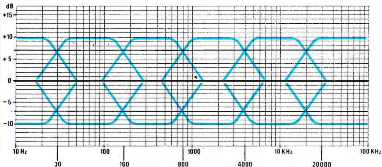
**Fig. 1** I quattro potenziometri presenti nell'equalizzatore agiscono ognuno nella porzione di gamma riportata in questo grafico. Tenendo il cursore in posizione centrale le frequenze interessate non vengono amplificate né attenuate, spostando il cursore tutto verso l'alto il segnale verrà amplificato di circa 10 dB. spostandolo tutto verso il basso il segnale verrà invece attenuato di 10 dB.
