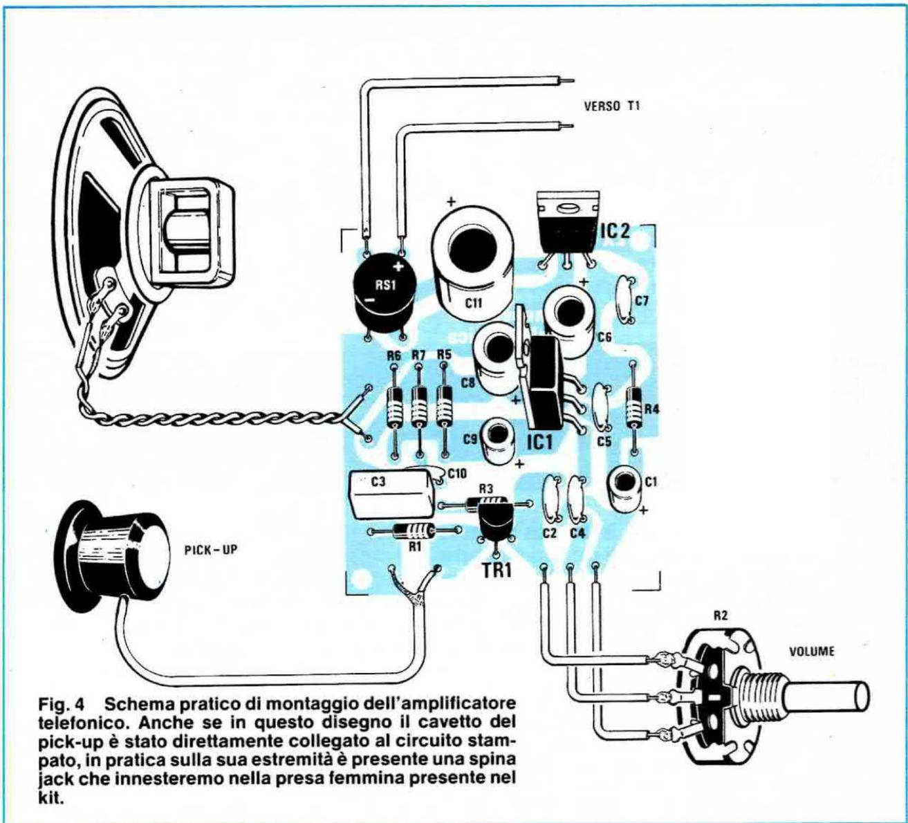
**Fig. 4** Schema pratico di montaggio dell'amplificatore telefonico. Anche se in questo disegno il cavetto del pick-up è stato direttamente collegato al circuito stampato, in pratica sulla sua estremità è presente una spina jack che innesteremo nella presa femmina presente nel kit.
