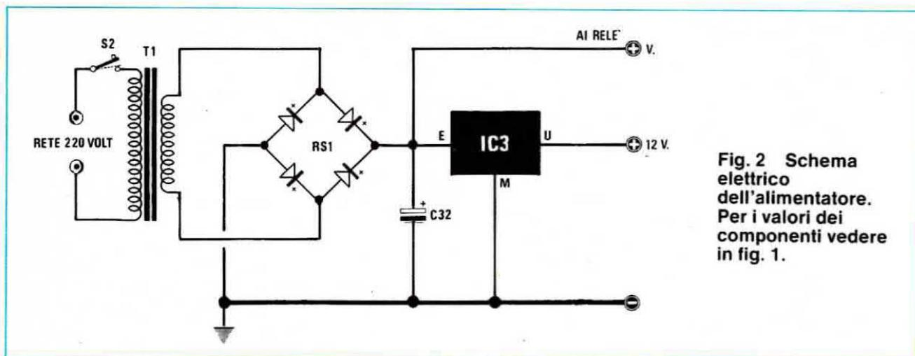
**Fig. 2** Schema elettrico dell'alimentatore. Per i valori dei componenti vedere in fig. 1.
