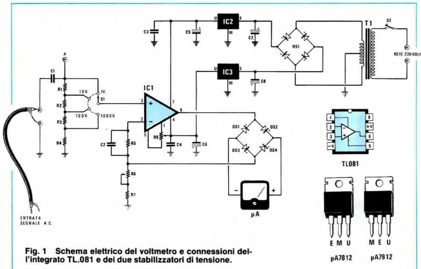
**Fig. 1** Schema elettrico del voltmetro e connessioni dell'integrato TL.081 e dei due stabilizzatori di tensione.
