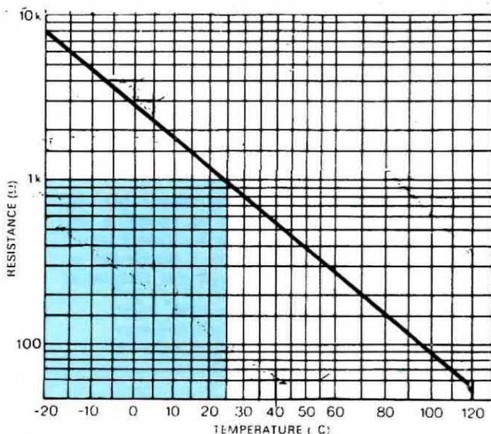
**Fig. 2** Da questo grafico si può notare che le due resistenze NTC da noi fornite, ad una temperatura di 25° gradi presentano una resistenza ohmica di 1.000 ohm. Ad una temperatura massima di 120 gradi tali resistenze si riducono a meno di 70 ohm mentre ad una minima di -20 gradi avremo il massimo di resistenza cioè circa 10.000 ohm.
