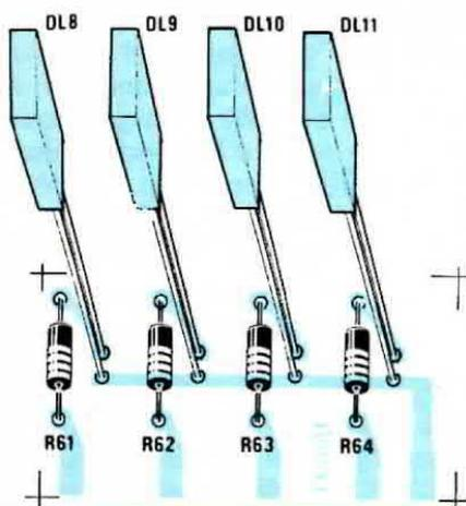
**Fig. 11** Schema pratico di montaggio dei due circuiti stampati LX.500/D e LX.500/E. Tutte le resistenze presenti su questi due circuiti sono tutte da 680 ohm  $\frac{1}{4}$  di watt come riportato nella lista dei componenti (vedi R54 a R64). Prima di staginare i diodi led dovrete staginare i due circuiti sui terminali dei commutatori a slitta come indicato in fig. 2.
