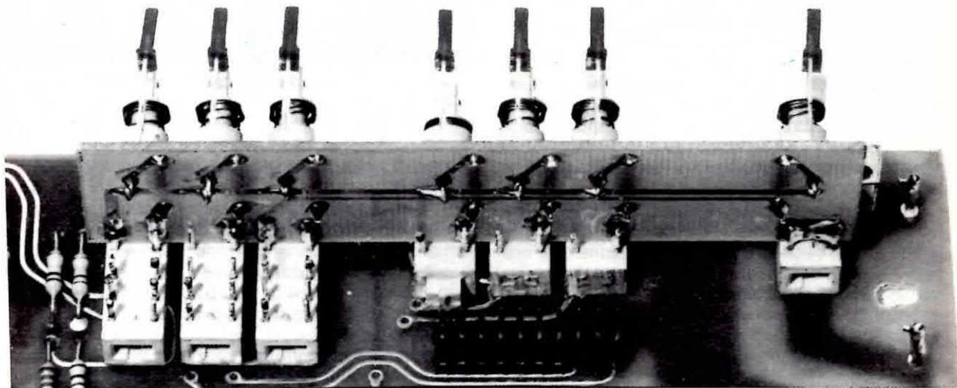
I circuiti stampati LX.500/D e LX.500/E li stagneremo sui terminali che sporgono superiormente dai commutatori a slitta, prima di fissare i diodi led. Dopodiché fisseremo provvisoriamente il circuito stampato LX.500/B dentro il mobile e stagneremo i diodi led in modo che questi entrino perfettamente nella fessura presente sul pannello frontale.
