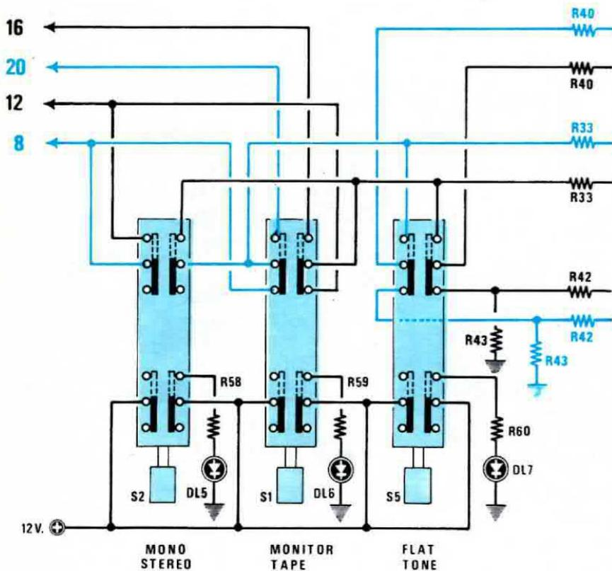
**Fig. 8** Schema elettrico dei commutatori relativi alle funzioni Mono/Stereo-Monitor-Flat. Anche qui per individuare i componenti dei due canali li abbiamo stampati in due diversi colori.
