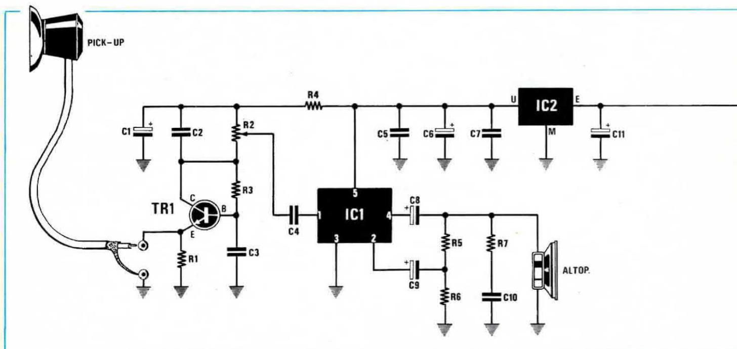
Se volete poter ascoltare meglio la voce di chi vi telefona oppure se volete che anche altri, insieme a voi, possano ascoltare la risposta del vostro interlocutore, realizzate questo semplice amplificatore telefonico in grado di captare induttivamente la conversazione e di potenziare il segnale senza per questo dover manomettere l'impianto nè dovergli collegare alcun filo.
