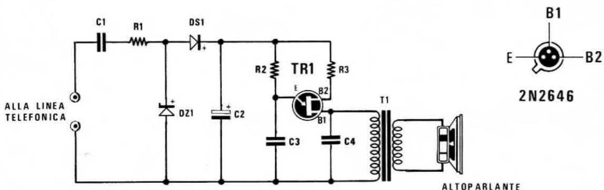
raddrizzare la tensione alternata di chiamata dalla linea telefonica, ridurla a 20 volt (tramite DZ1) e convertirla in tensione continua tramite DS1 - CZ per poter alimentare l'oscillatore.
