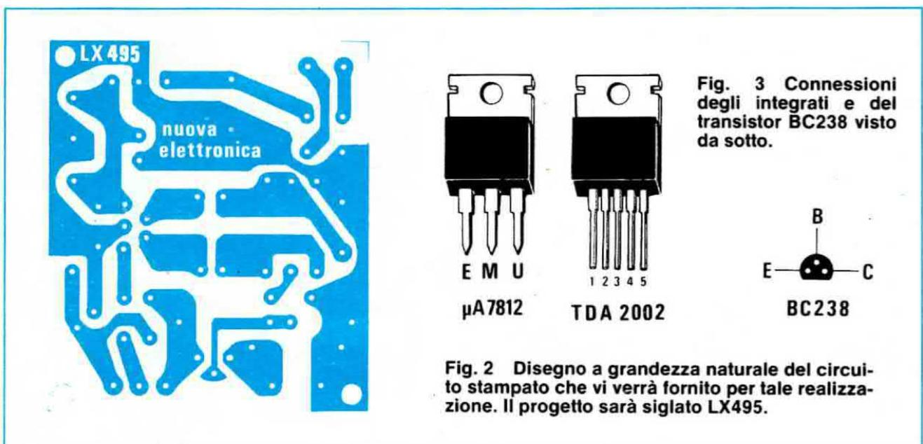
Fig. 3 Connessioni degli integrati e del transistor BC238 visto da sotto.
