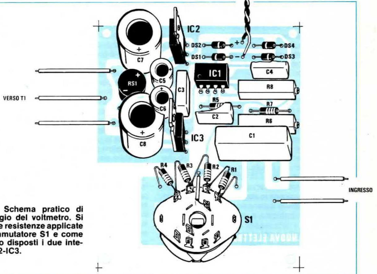
Fig. 3 Schema pratico di montaggio del voltmetro. Si notino le resistenze applicate sul commutatore S1 e come risultano disposti i due integrati IC2-IC3.
