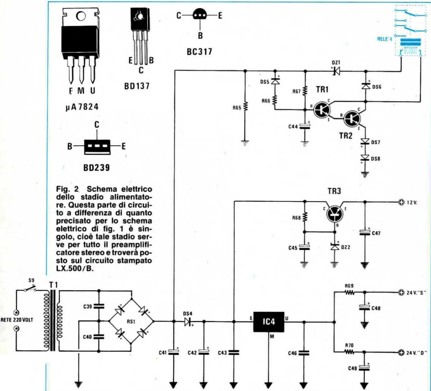
Fig. 2 Schema elettrico dello stadio alimentatore. Questa parte di circuito a differenza di quanto precisato per lo schema elettrico di fig. 1 è singolo, cioè tale stadio serve per tutto il preamplificatore stereo e troverà posto sul circuito stampato LX.500/B.
