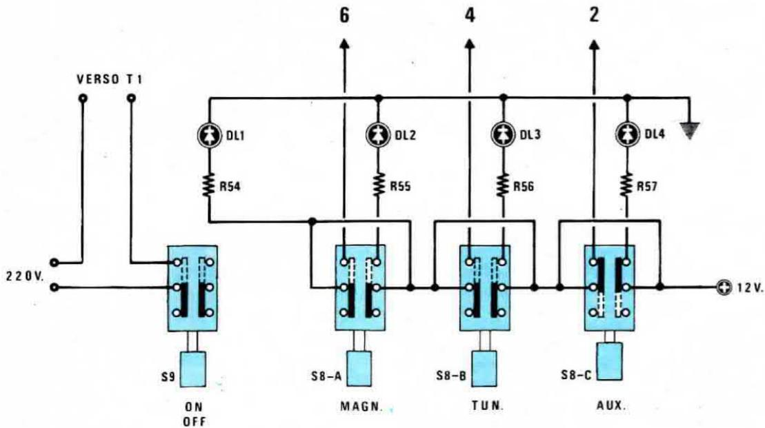
**Fig. 7** Schema elettrico dei commutatori degli ingressi Magnetico, Tuner-Auxiliario e di quello di rete. I numeri riportati in alto sono quelli dell'alimentatore dei relè N1-N2-N3 (vedi schema di fig. 1). Pigiando un interruttore automaticamente si accenderà il diodo led ad esso collegato.
