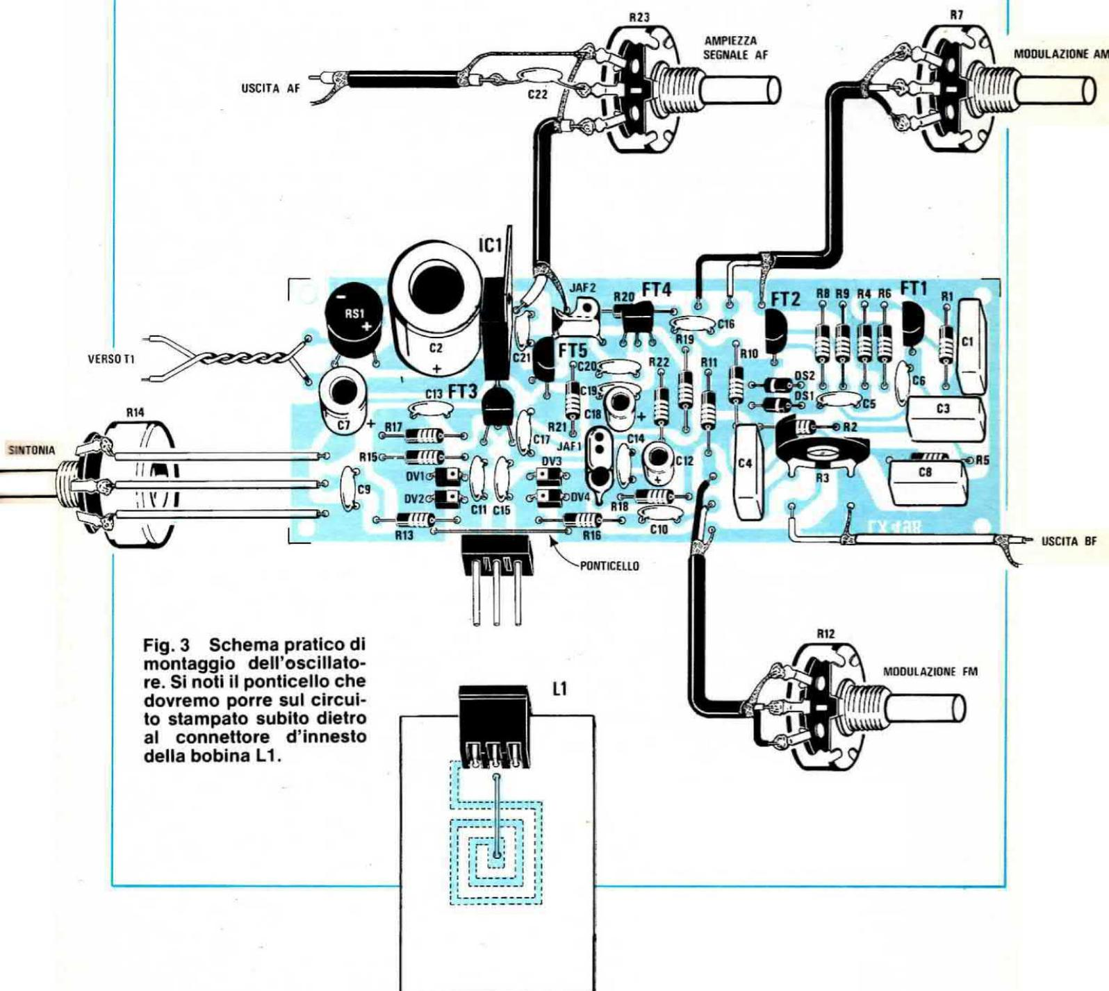
Fig. 3 Schema pratico di montaggio dell'oscillatore. Si noti il ponticello che dovremo porre sul circuito stampato subito dietro al connettore d'innesto della bobina L1.
