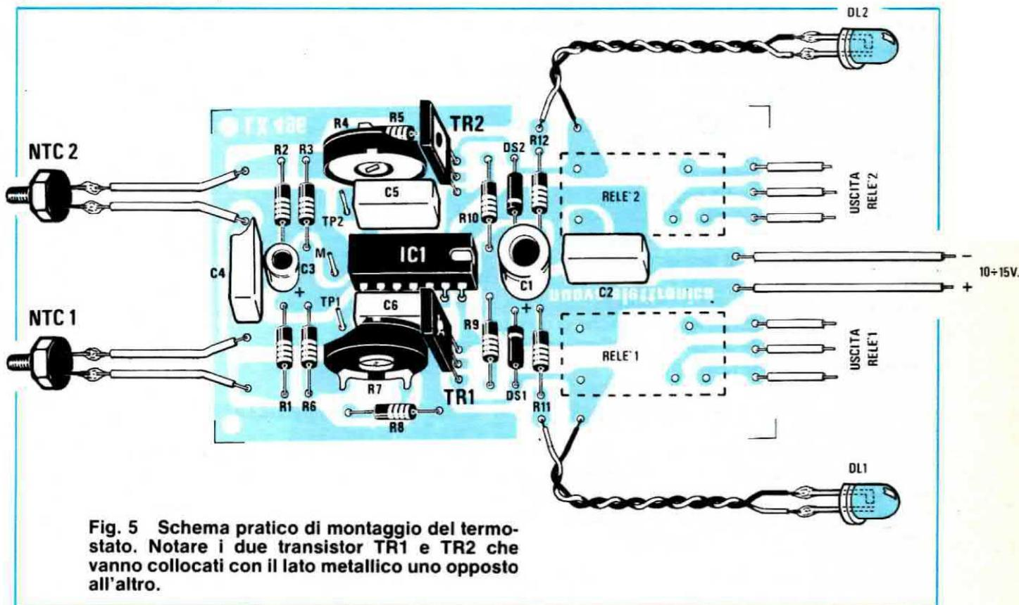
Fig. 5 Schema pratico di montaggio del termostato. Notare i due transistor TR1 e TR2 che vanno collocati con il lato metallico uno opposto all'altro.
