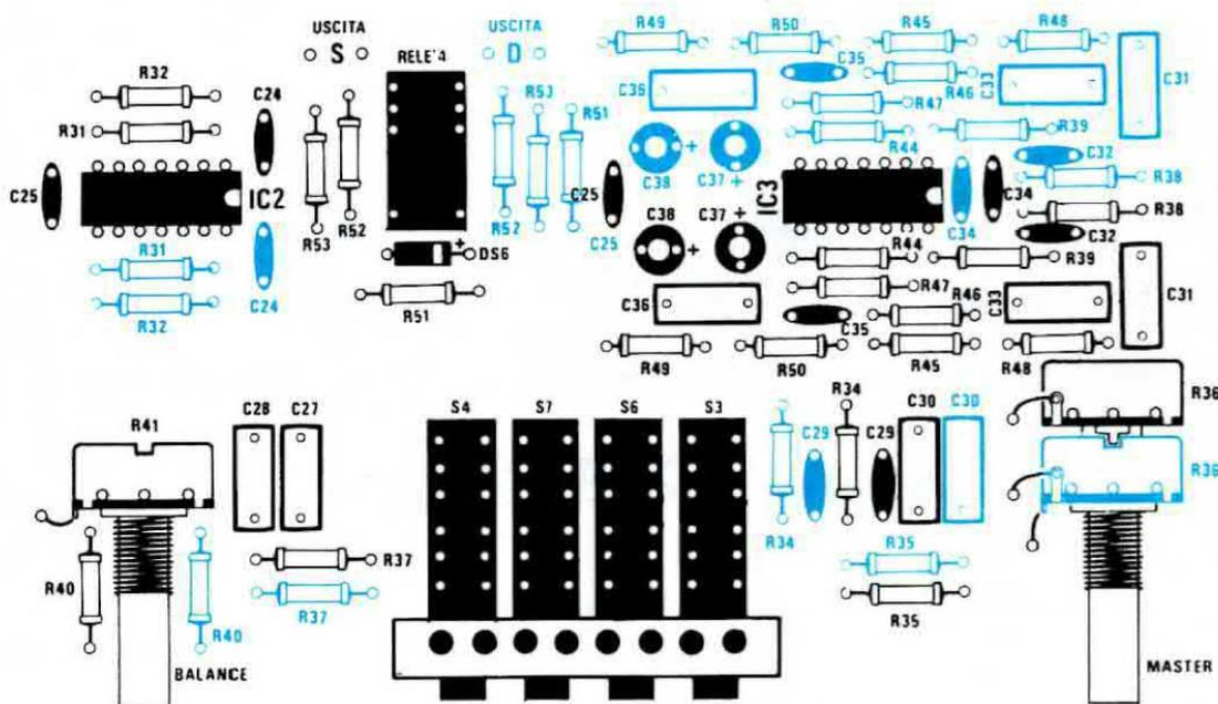
**Fig. 5** Schema pratico di montaggio del telaio LX.500/A. Notare i collegamenti tra il terminale centrale delle boccole d'ingresso e il circuito stampato, e il connettore maschio necessario per la piattina di collegamento.
