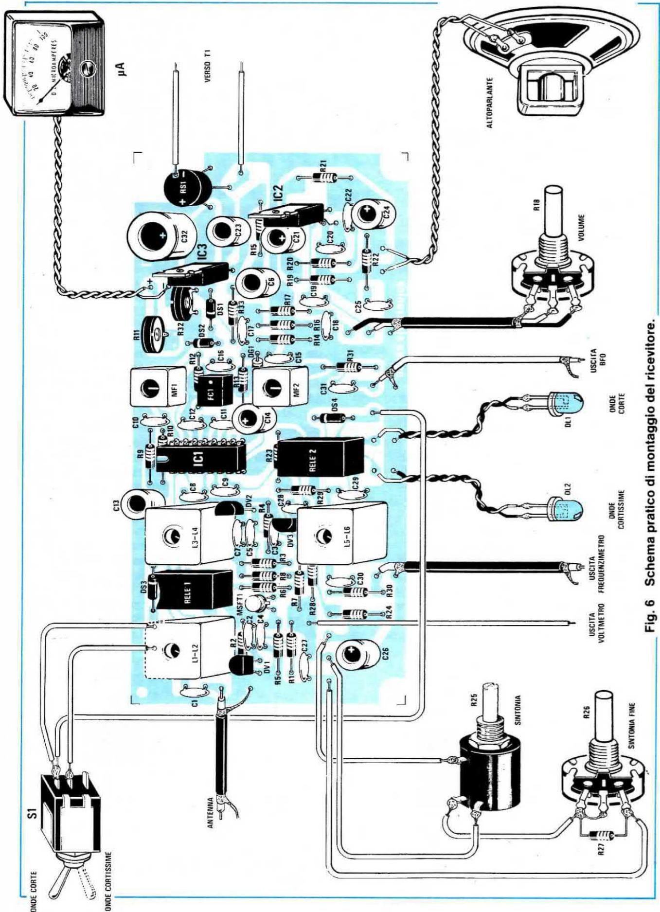
Fig. 6 Schema pratico di montaggio del ricevitore.
