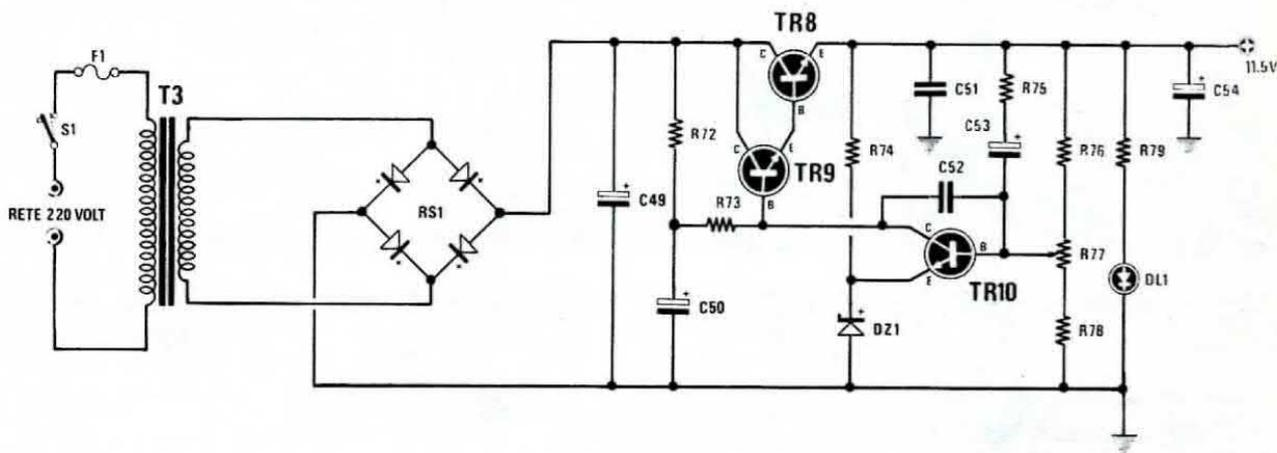
**Fig. 2** Schema elettrico dell'alimentatore del monitor per microcomputer. Il trimmer R77 serve per regolare la tensione d'uscita sul valore richiesto, cioè 11,5 volt. Per i valori dei componenti vedere la lista riportata nella pagina di sinistra.
