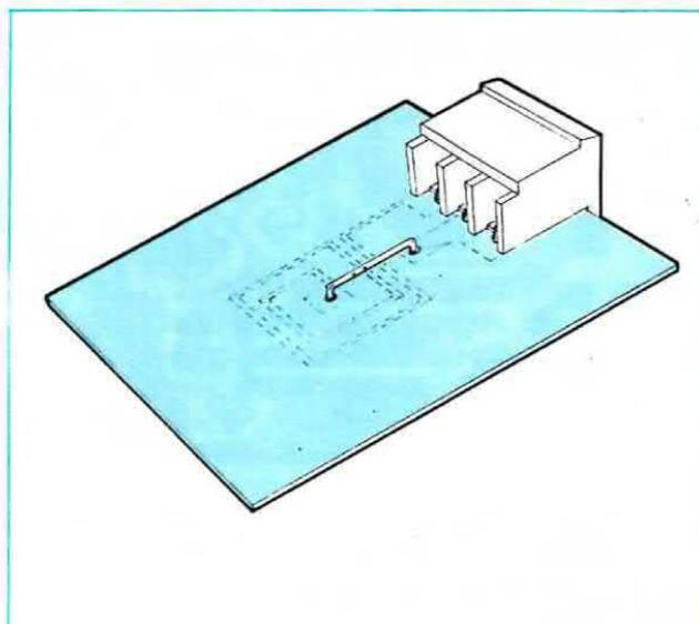
**Fig. 5** Il connettore femmina andrà prima innestato sui bordi dello stampato poi ripiegato su di esso in modo che i suoi terminali entrino nei tre fori presenti sul circuito stampato dopodiché si potrà procedere alla stagnatura dei terminali.
