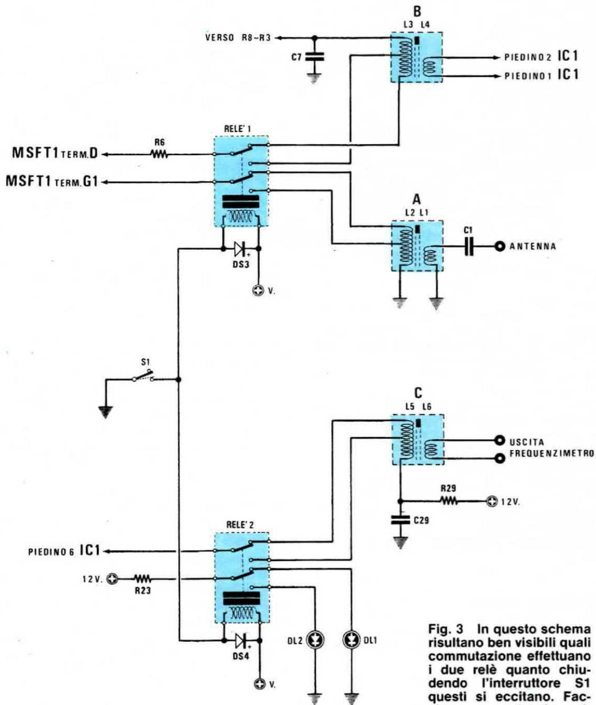
Fig. 3 In questo schema risultano ben visibili quali commutazione effettuano i due relè quanto chiudendo l'interruttore S1 questi si eccitano. Facciamo presente che sull'involucro della bobina L1/L2 è riportata la sigla 499/A nella L3/L4 il numero 499/B e su quella oscillatrice L5/L6 il numero 499/C. Montando le tre bobine sul circuito stampato dovremo fare attenzione a inserirle nell'esatta posizione.
