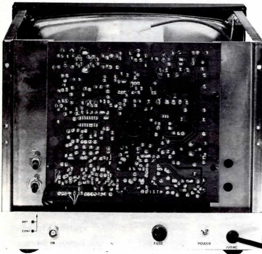
Qui di lato è visibile il circuito stampato fissato posteriormente nel telaio di sostegno. I due potenziometri, visibili in basso sulla sinistra, sono quelli che regolano la luminosità ed il contrasto.
