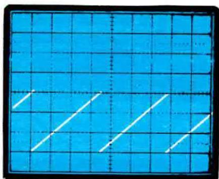
**Fig. 9** Nel punto G ci apparirà sullo schermo questa onda a dente di sega
