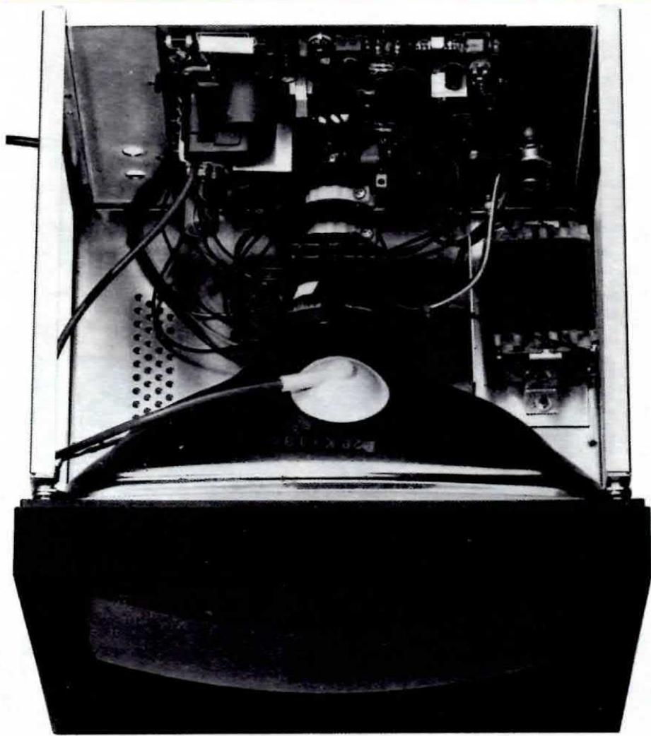
**Foto del monitor visto dall'alto. Facciamo presente che tutto il telaio di sostegno interno è zincato in color oro, mentre il mobile esterno è verniciato a fuoco in color beige.**
