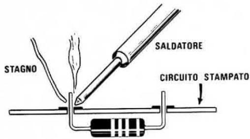
**Fig. 10** Per eseguire delle ottime stagnature occorre appoggiare la punta del saldatore vicino al terminale interessato e il filo dello stagno del lato opposto. Sciolta una goccia di stagno si lascerà il saldatore fino a quando questo non si sarà ben amalgamato attorno al terminale e sul circuito stampato.
