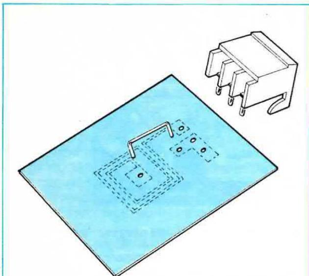
**Fig. 4** In possesso delle tre bobine incise su circuito stampato, dovremo applicare come vedesi in disegno un ponticello tra il foro centrale dello stampato e quello d'innesto dello zoccolo. Ovviamente le due estremità di tale ponticello andranno stagnate sulle piste.
