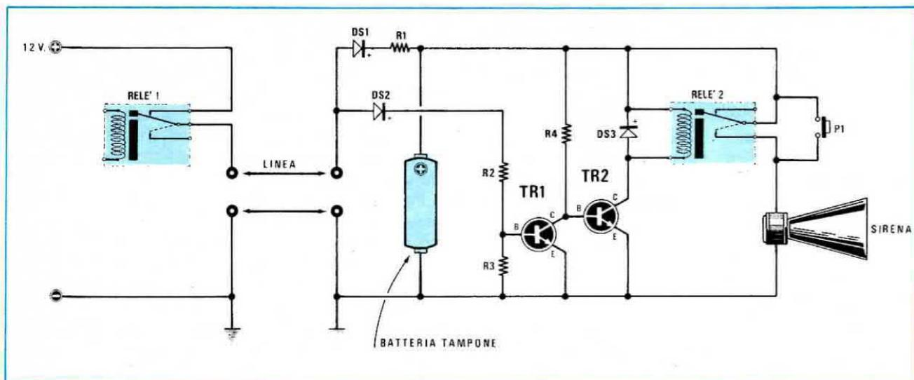
dalla batteria dell'antifurto raggiunte il modulo tamper, in tale condizione la base del transistor TR1 viene polarizzata positivamente tramite R2 e DS2 quindi conducendo toglie la polarizzazione alla base di TR2 quindi il relè risulta diseccitato.
