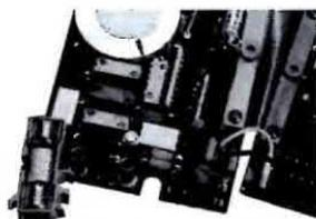
Per proteggere te e i tuoi multimetri in caso di sovraccarico accidentale, usiamo varistori in metaloxide, diodi, termistori e resistori più di ogni altro costruttore di multimetri a basso costo.
