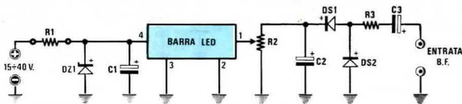
**Fig. 5** Schema elettrico del circuito Vu-Meter.
