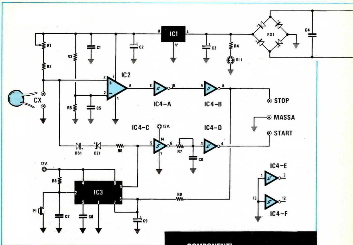
Se la differenza di potenziale ai capi di CX si annullasse, l'integrato IC2 si interdirebbe con conseguenti ritardi e anomalie di funzionamento.
