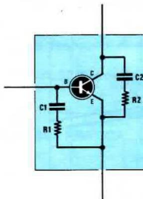
**Fig. 13** Questa conversione da parallelo a «serie» nelle formule riportate da fig. 14 a fig. 22 sono già considerate, quindi il lettore nei suoi calcoli dovrà utilizzare solo e sempre i valori di capacità e resistenza in configurazione «parallelo».
