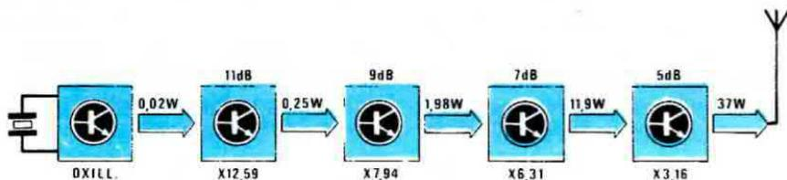
**Fig. 7** Se la potenza AF erogata dallo stadio oscillatore è irrisoria, occorreranno più stadi amplificatore AF per poter raggiungere la potenza desiderata. Conoscendo di ogni transistor amplificatore il Gpe espresso in dB., potremo calcolare in linea di massima la potenza che ricaveremo in uscita su ogni stadio.
