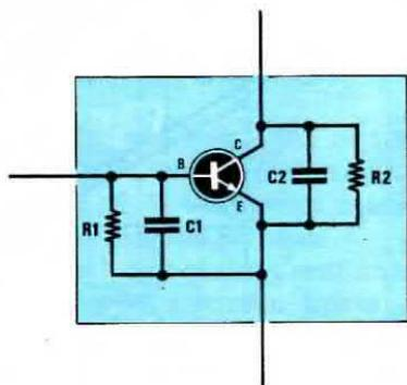
**Fig. 12** I valori di capacità e resistenza di Base e di capacità e resistenza di Collettore risultano quasi sempre riportati in configurazione «parallelo». A seconda del tipo di accoppiamento utilizzati questi valori a volte occorre convertirli da parallelo a «serie» vedi fig. 13.
