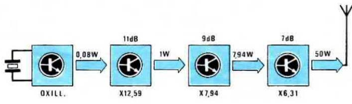
**Fig. 8** Utilizzando uno stadio oscillatore che eroga maggior potenza ci occorreranno meno stadi amplificatori per ottenere in uscita una potenza superiore.
