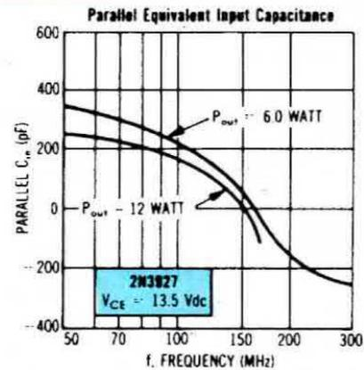
**Fig. 23** Esistono particolari transistor la cui capacità di Base (e a volte anche quella di Collettore) al variare della frequenza si annulla o diventa negativa. Questo transistor ad esempio lavorando a 50 MHz presenta una capacità di circa 300 pF, a 150 MHz invece di 0 pF.
