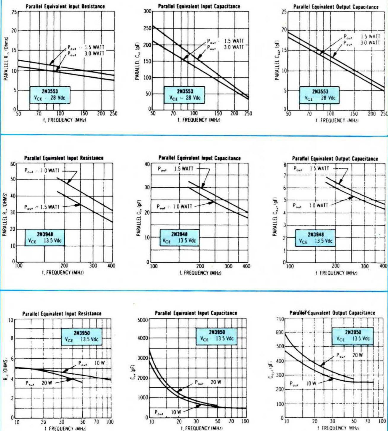
**Fig. 11** Per comprendere come possono variare queste capacità di base e di collettore al variare della frequenza di lavoro e della potenza erogata vi riportiamo i grafici di tre transistor. A sinistra è riportato il valore della resistenza di Base, al centro la capacità della Base e sulla destra la capacità di Collettore.
