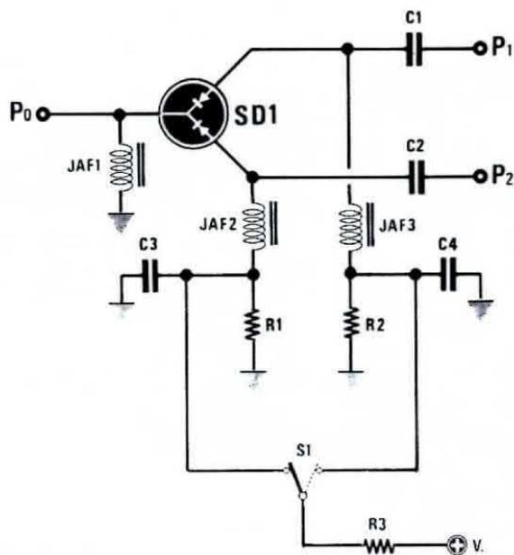
**Fig. 7** Per poter commutare P1 su P0 o P2 su P0 dovremo semplicemente applicare una tensione positiva sul terminale interessato. Il valore ohmico di R3 andrà scelto per far scorrere nei diodi circa 40-60 milliamper. Per le impedenze JAF e i condensatori C1 e C2 vedere i valori dello schema di fig. 8. Per R1-R2 potremo adottare 1.200-1.500 ohm mentre per C3-C4 dei condensatori ceramici VHF da 1.000 pF.
