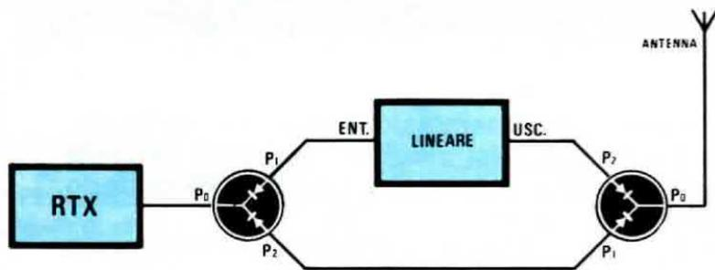
**Fig. 4** Se volessimo applicare un lineare AF di potenza, sull'uscita di un ricetrasmittitore, ci occorrerebbero due diodi collegati come vedesi da schema.
