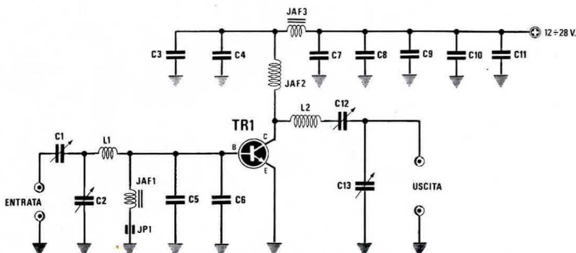
Fig. 1 Schema elettrico del lineare da 60 Watt idoneo per la FM da 88 a 146 MHz.
