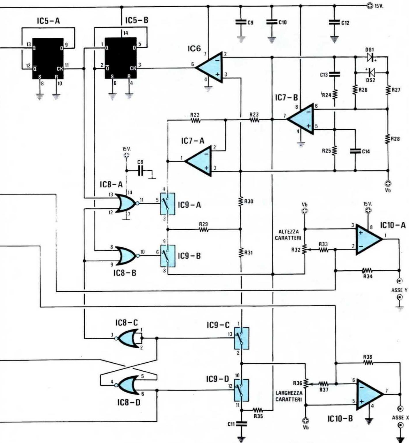
Fig. 5 Schema elettrico dell'analizzatore grafico per integrati TTL e C.Mos. Sulla sinistra è visibile lo «zoccolo sonda» da innestare nel circuito sotto prova, e in alto lo zoccolo Textool entro al quale inseriremo l'integrato tolto da tale circuito. Come spiegato nell'articolo ci servono i terminali VP (visibili sulla sinistra) per prelevare la tensione di riferimento dal circuito di alimentazione sotto controllo. Per la lista componenti vedere la fig. 6 della pagina seguente.
