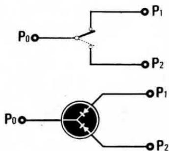
**Fig. 2** Il sistema più semplice per capire come utilizzare questo commutatore elettronico è quello di considerarlo un normale deviatore a levetta, dove P0 potrebbe corrispondere al terminale centrale di commutazione.
