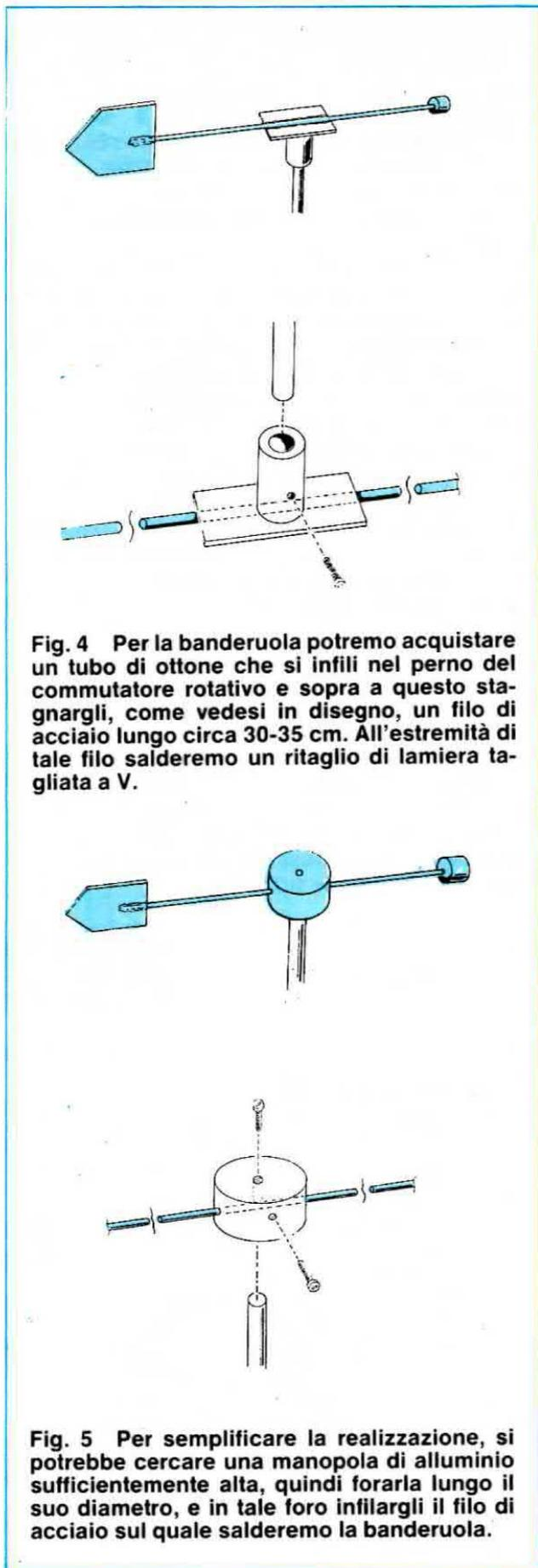
Fig. 4 Per la banderuola potremo acquistare un tubo di ottone che si infili nel perno del commutatore rotativo e sopra a questo stagnergli, come vedesi in disegno, un filo di acciaio lungo circa 30-35 cm. All'estremità di tale filo salderemo un ritaglio di lamiera tagliata a V.
