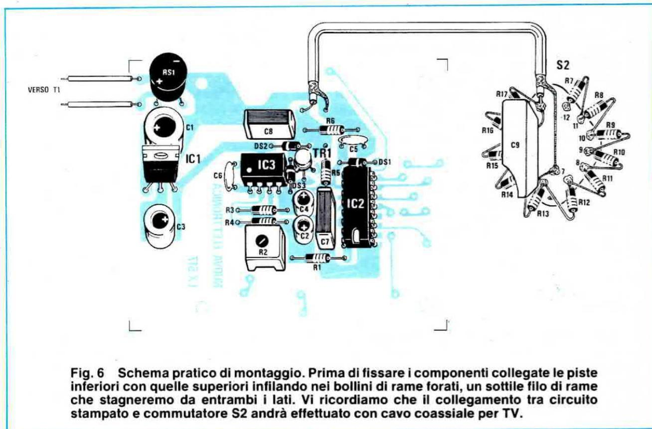
Fig. 6 Schema pratico di montaggio. Prima di fissare i componenti collegate le piste inferiori con quelle superiori infilando nei bollini di rame forati, un sottile filo di rame che stagneremo da entrambi i lati. Vi ricordiamo che il collegamento tra circuito stampato e commutatore S2 andrà effettuato con cavo coassiale per TV.
