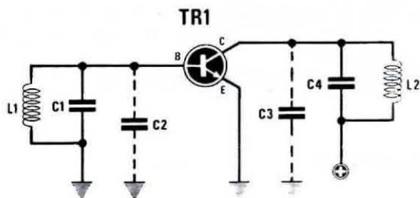
**Fig. 10** Nei calcoli delle bobine e capacità di accordo occorre sempre tener presente che esiste una capacità interna del transistor (vedi C2 e C3) sia sulla base che sul collettore. Questi valori non risultano fissi, ma variano al variare della frequenza di lavoro, della tensione di alimentazione e della potenza di uscita.
