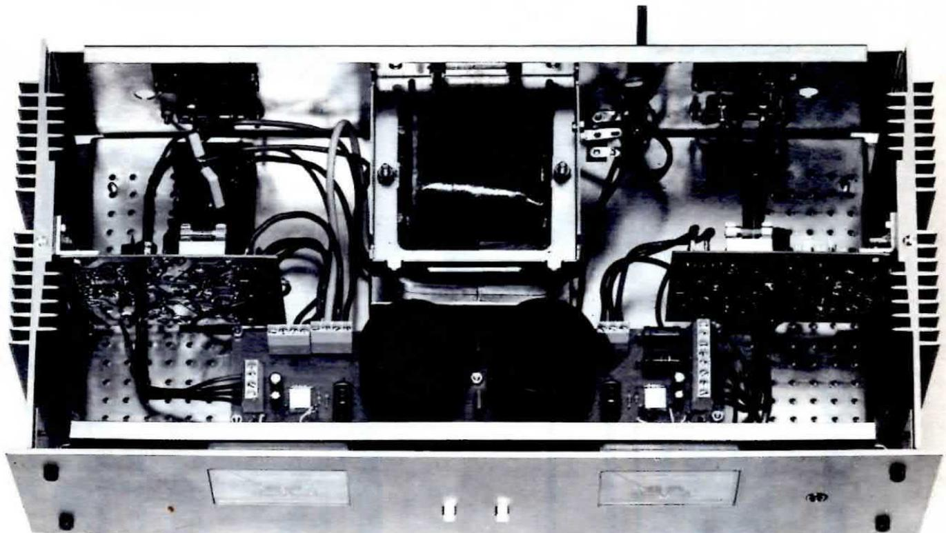
Il trasformatore di alimentazione verrà collocato orizzontalmente e fissato con due viti sul pannello posteriore. È consigliabile tenere i fili di uscita in basso. Il circuito stampato dell'alimentatore verrà posto frontalmente al trasformatore come risulta visibile in queste due foto.
