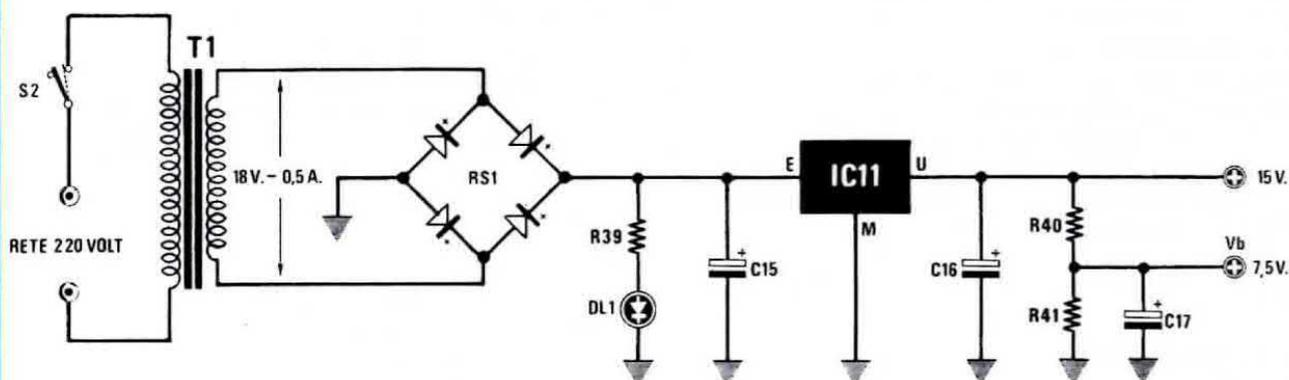
Fig. 6 Schema elettrico dell'alimentatore dell'analizzatore grafico. Il terminale Vb = 7,5 volt viene già collegato tramite le piste del circuito stampato nei punti richiesti. In alto la lista completa dei componenti richiesti dall'analizzatore grafico.
