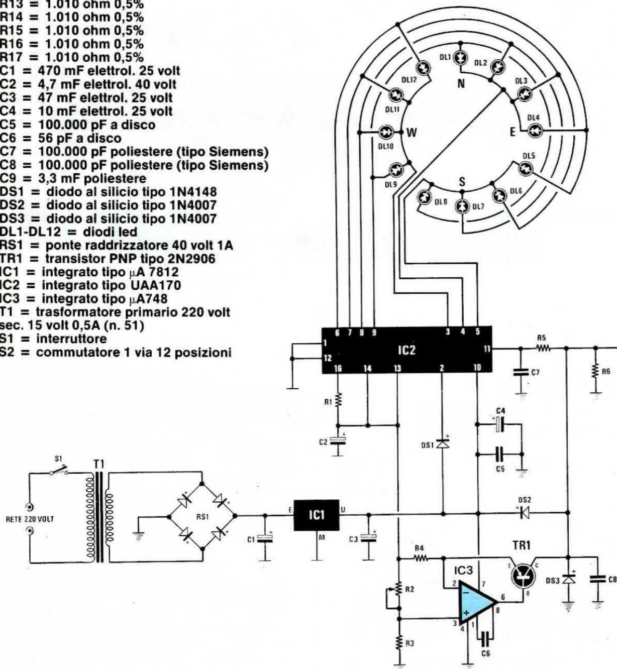
cheremo 11 resistenze di precisione ad alta stabilità termica da 1010 ohm.
