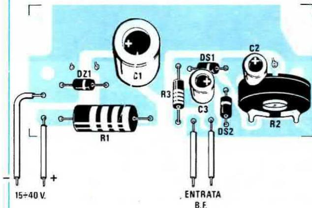
**Fig. 7** Schema pratico di montaggio del Vu-Meter. Dalla parte opposta di tale circuito fisseremo la barra a diodi led e poiché questa si inserirà solo nella sua giusta posizione, non dovremo preoccuparci dei quattro terminali presenti.
