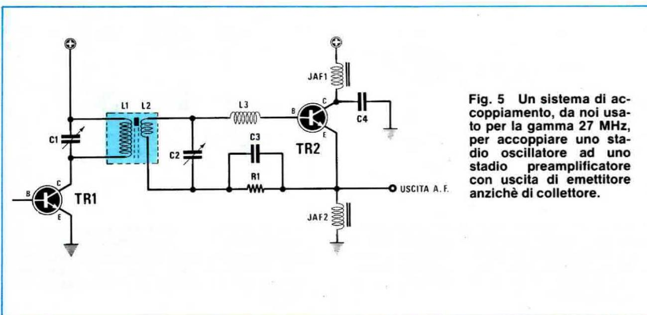
Fig. 5 Un sistema di accoppiamento, da noi usato per la gamma 27 MHz, per accoppiare uno stadio oscillatore ad uno stadio preamplificatore con uscita di emettitore anziché di collettore.
