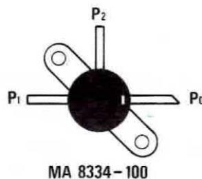
Fig. 1 Connessioni del diodo Switch. viste da sopra.
