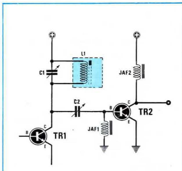
Fig. 2 Anziché effettuare un accoppiamento induttivo come riportato in fig. 1, lo potremo effettuare capacitivo, collegando il collettore dell'oscillatore alla base del transistor preamplificatore, tramite un compensatore da 10/60 pF.
