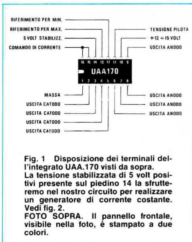
mente più complesso, e come vedesi in fig. 2, insieme all'integrato UAA 170 ci servirà un altro integrato uA 748 e un transistor, per realizzare un generatore di corrente costante al fine di rendere insensibile tutto il circuito alle variazioni di tensione di alimentazione e della temperatura atmosferica.
