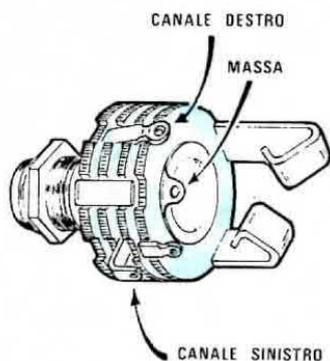
**Fig. 8 Sulla morsettiere dell'alimentatore (vedi fig. 6 a destra) i tre fili indicati «verso cuffia sinistra» massa «verso cuffia destra» li dovremo collegare ai terminali di questa presa jack che in seguito fisseremo sul controllo del nostro mobile.**
