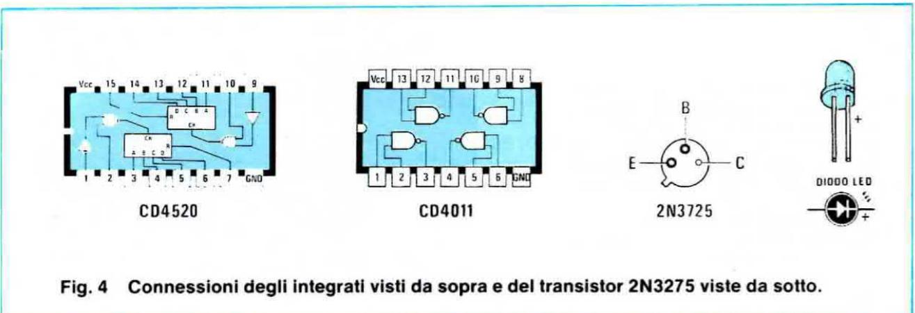
**Fig. 4** Connessioni degli integrati visti da sopra e del transistor 2N3275 viste da sotto.
