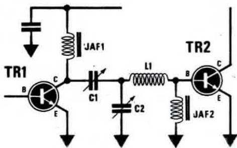
**Fig. 6** Per accoppiare due stadi amplificatori AF la schema più valido è quella di utilizzare questo filtro. In fig. 18 e 19 troveremo tutte le formule per calcolare i valori dei compensatore e delle bobine.
