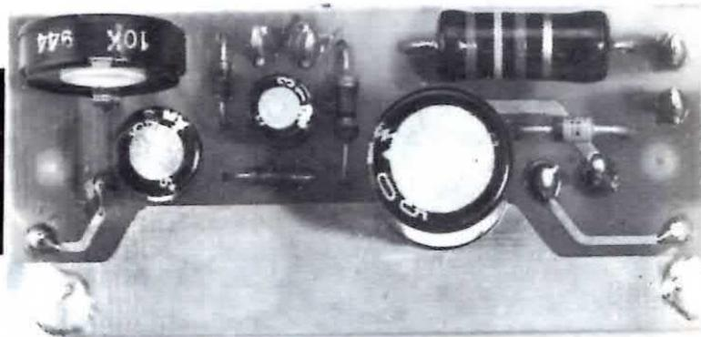
Ci è sembrato interessante presentare questo nuovo componente della Telefunken, in quanto con esso, è possibile realizzare dei vu-meter molto compatti che potranno facilmente trovare posto in qualsiasi tipo di mobile, anche in quelli della serie SLIM-LINE.
