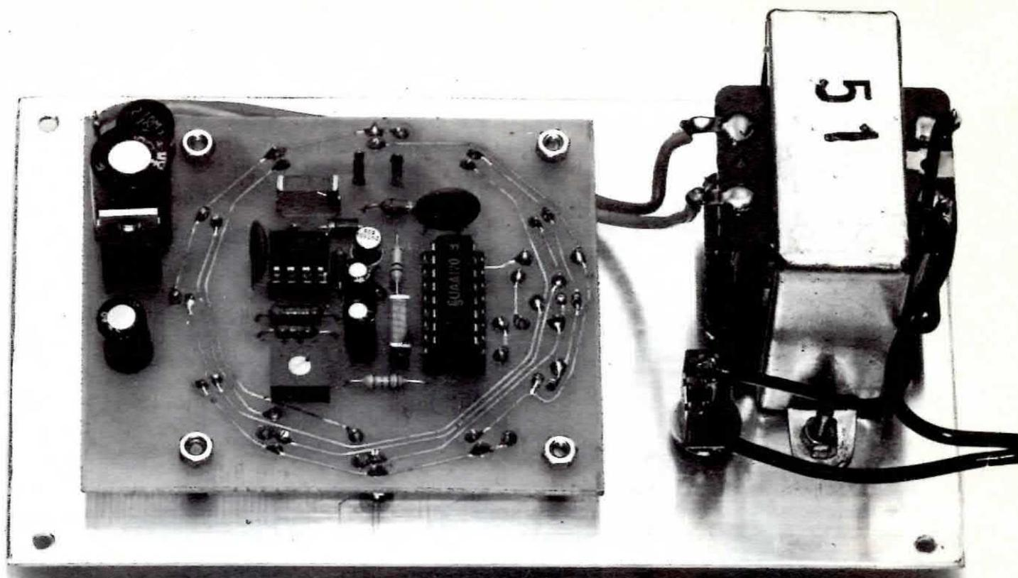
**Il circuito stampato lo dovremo fissare sotto al pannello frontale del mobile, tenendolo distanziato di qualche millimetro per evitare che qualche terminale non vada a toccare il metallo del pannello. Il trasformatore di alimentazione lo fisseremo con due viti sul lato destro.**
