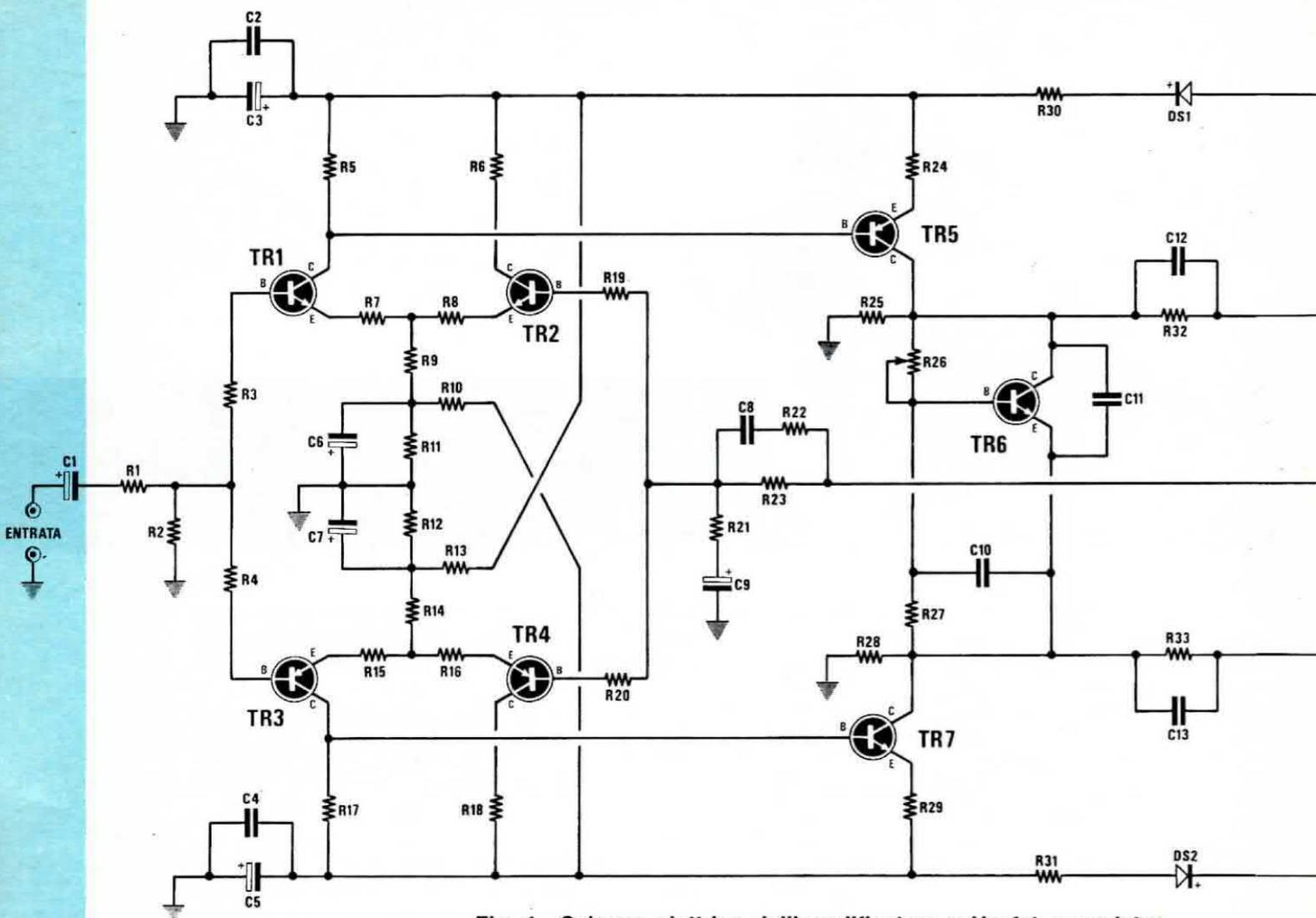
Fig. 1 Schema elettrico dell'amplificatore a Hexfet, completo del suo alimentatore (vedi schema in basso sulla destra).
