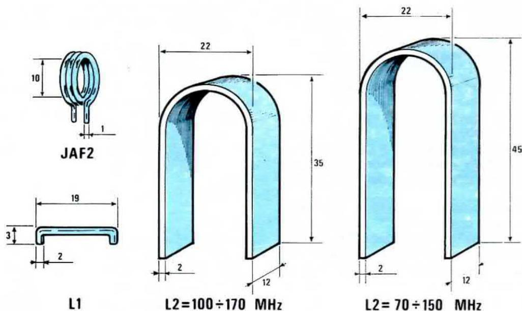
**Fig. 2** Misure in millimetri dell'impedenza JAF2 e delle due bobine richieste per la realizzazione di questo lineare. Le dimensioni della bobina L2 variano leggermente in funzione della frequenza di lavoro.
