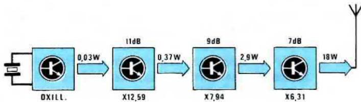
**Fig. 9** Passando dal calcolo teorico alla realizzazione pratica è normale rilevare in uscita una potenza inferiore di un 30% ed anche 40% per le perdite di AF.
