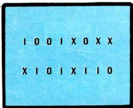
**Fig. 1** Sullo schermo dell'oscilloscopio vi appariranno contemporaneamente tutte le condizioni logiche presenti sui 16 o 14 terminali dell'integrato sotto prova. La X apparirà quando esiste una condizione anomala da impedire il regolare funzionamento dell'integrato.
