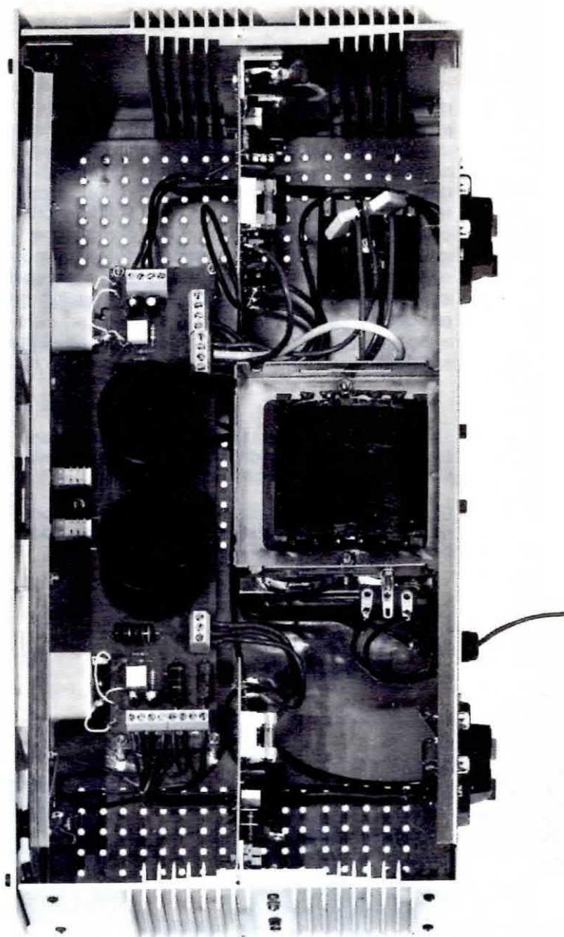
**Foto Sopra.** In questa foto si riesce meglio a distinguere la piccola aletta di raffreddamento sopra alla quale risulta fissato il ponte raddrizzatore di potenza RS1 e la piccola bassetta di ancoraggio provvista di tre terminali (fissata sul trasformatore di alimentazione) necessaria per i collegamenti del cordone di alimentazione 220 volt.
