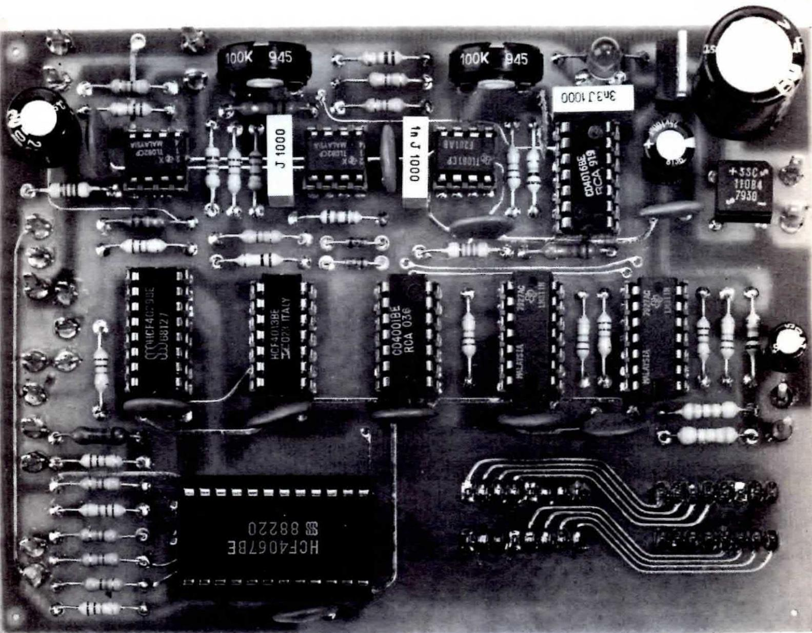
**Guardando la foto di questo montaggio si può subito intuire che la realizzazione di questo analizzatore grafico è molto semplice. Risultando il circuito stampato a fori metallizzati il risultato è assicurato.**
