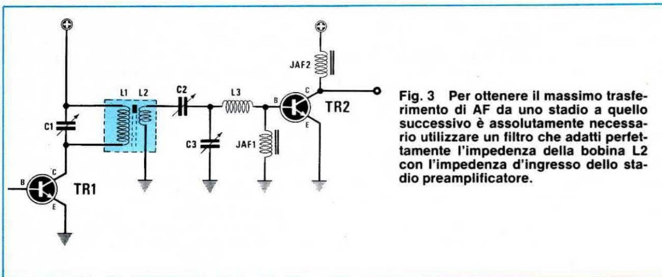
Fig. 3 Per ottenere il massimo trasferimento di AF da uno stadio a quello successivo è assolutamente necessario utilizzare un filtro che adatti perfettamente l'impedenza della bobina L2 con l'impedenza d'ingresso dello stadio preamplificatore.
