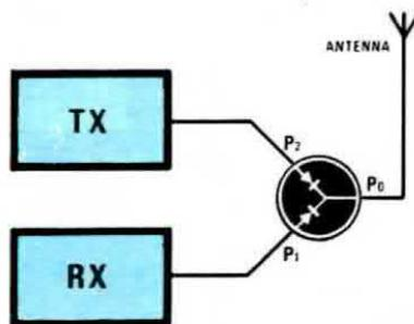
**Fig. 3** Se avessimo un ricevitore ed un trasmettitore da collegare alternativamente ad un'unica antenna è ovvio che il terminale P0 lo dovremo collegare all'antenna e i terminali P1 e P2 agli ingressi RX e TX.
