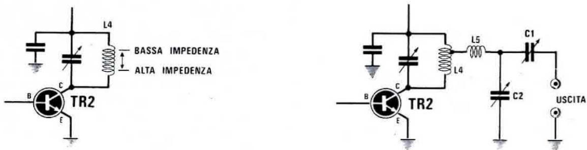
**Fig. 2** Quando l'impedenza di collettore risulta, come nel nostro caso, maggiore di 52 ohm, occorre accordare il collettore con una bobina e una capacità, prelevando il segnale per l'uscita sulla seconda o terza spira dal lato freddo come vedesi in figura.
