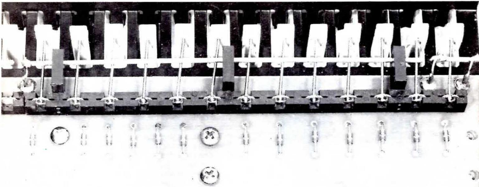
**Fig. 10** In questa foto è chiaramente visibile la barra portaterminali con le mollette già agganciate con una estremità sui terminali di ancoraggio e l'altra sui tasti della tastiera. Controllate, dopo aver infilato le mollette, se pigiando i tasti queste vadano a toccare la barra di contatto.
