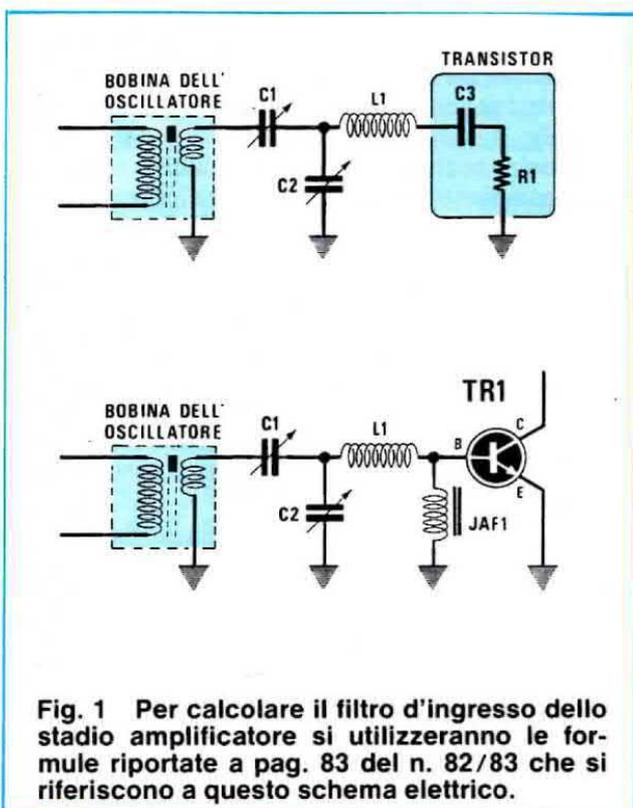
Fig. 1 Per calcolare il filtro d'ingresso dello stadio amplificatore si utilizzeranno le formule riportate a pag. 83 del n. 82/83 che si riferiscono a questo schema elettrico.
