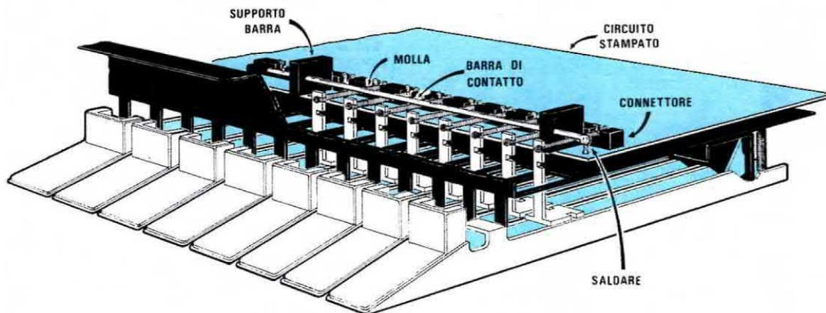
**Fig. 11** Il circuito stampato LX.519 dovrà essere fissato sul piano metallico inferiore della tastiera. Sul piano della tastiera dovrebbero già risultare inserite in corrispondenza della viti a croce (vedi foto sopra) delle rondelle di plastica bianca, che permetteranno di tenere distanziato di circa 4 mm il circuito dalla tastiera.
