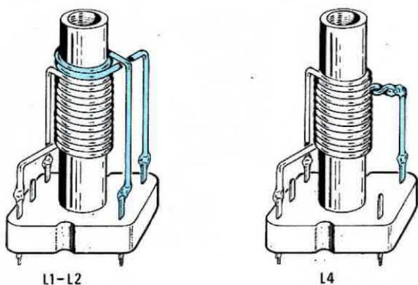
**Fig. 5** Come si vede in questo disegno, la bobina L2 andrà avvolta sopra a L1 dal lato freddo, cioè sul terminale che andrà a collegarsi a JAF1 - C1-C2. Per la L4 dovremo effettuare una presa alla 3<sup>a</sup> spira sempre verso il lato freddo, come spiegato nell'articolo.
