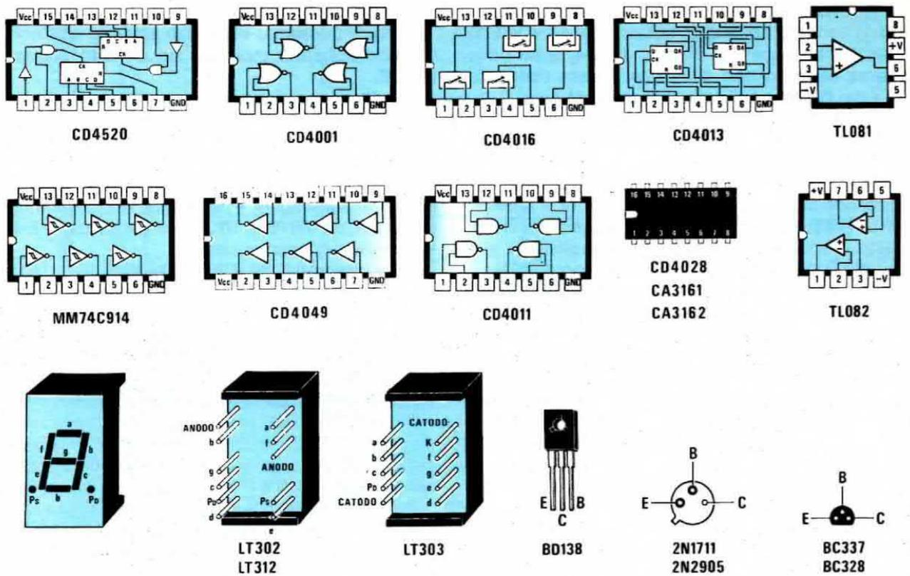
Fig. 3 Connessioni di tutti gli integrati, transistor e display utilizzati in tale progetto.
