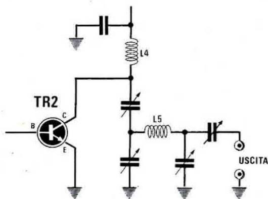
**Fig. 3** Anziché prelevare l'AF sulla seconda o terza spira della bobina di accordo per ottenere un segnale a bassa impedenza, si potrebbe adottare la soluzione visibile in figura, cioè realizzare un partitore capacitivo. Il sistema riportato in fig. 2 risulta comunque più semplice sia da realizzare che da tarare.
