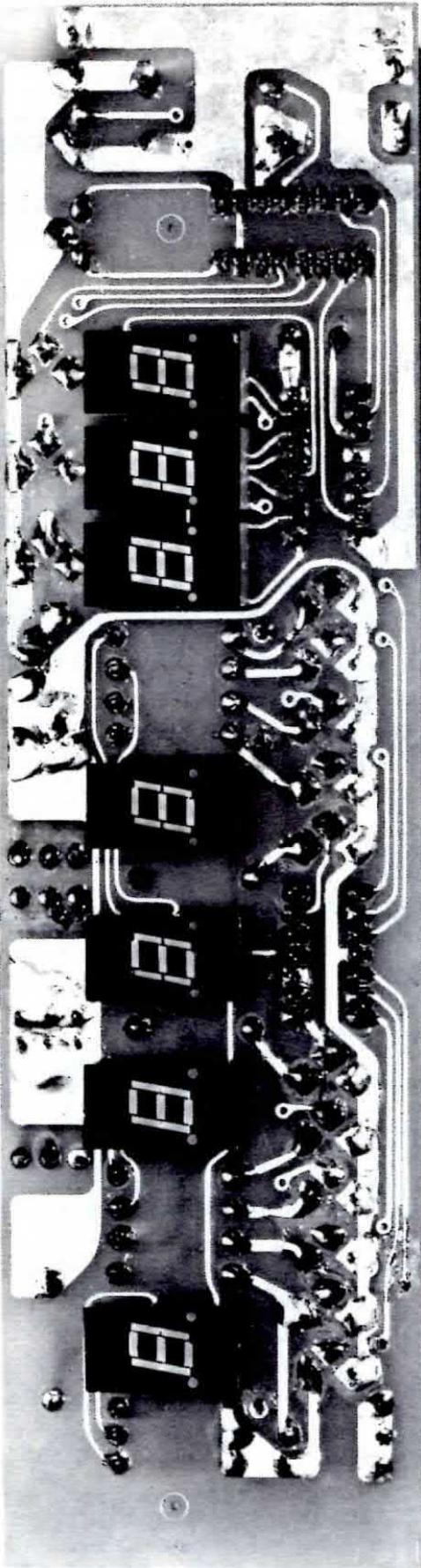
Foto del circuito di visualizzazione visto dal lato dei display. Inserendo i display sul circuito stampato, controllate che il punto decimale di questi risulti collocato verso il basso come visibile nella foto.
