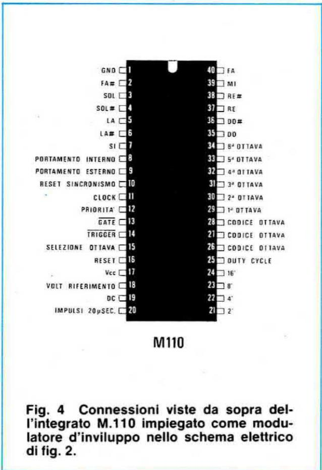
Fig. 4 Connessioni viste da sopra dell'integrato M.110 impiegato come modulatore d'involuppo nello schema elettrico di fig. 2.
