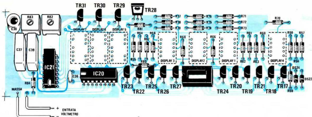
Fig. 6 Schema pratico di montaggio del circuito di visualizzazione visto dal lato componenti. Qui sotto si potrà vedere, come dovrete disporre i due circuiti stampati per innestare correttamente, gli zoccoli della piattina.
