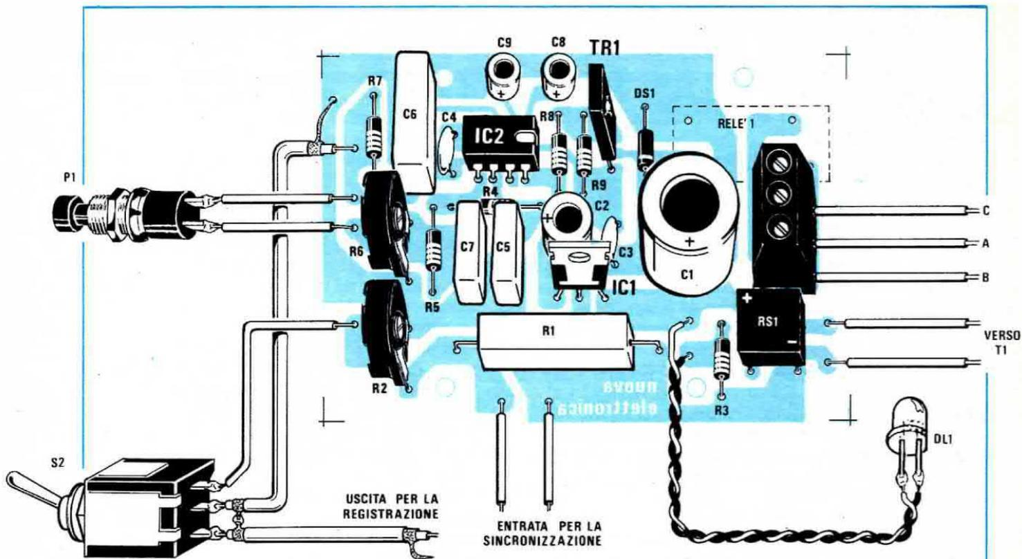
**Fig. 6** Schema pratico di montaggio del sincronizzatore. Per registrare il segnale di uscita dei 1.000 Hz si consiglia di utilizzare del cavetto schermato (vedi S2), mentre per l'ingresso del segnale di sincronizzazione si userà invece del comune filo di rame isolato in plastica. Dei tre terminali C-A-B di uscita utilizzerete solo i due indicati con le lettere A-B.
