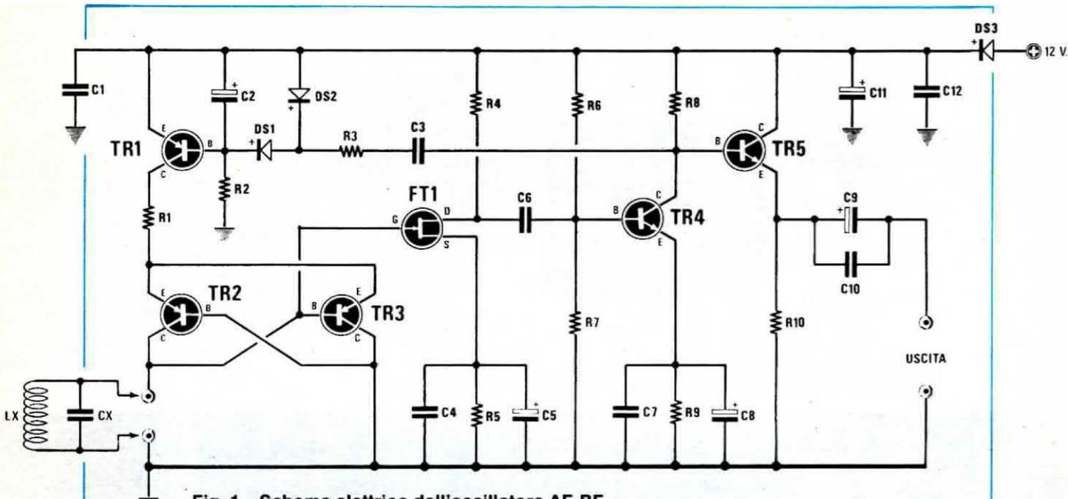
Fig. 1 Schema elettrico dell'oscillatore AF-BF.
