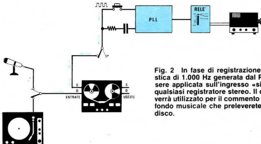
**Fig. 2** In fase di registrazione la nota acustica di 1.000 Hz generata dal PLL dovrà essere applicata sull'ingresso «sinistro» di un qualsiasi registratore stereo. Il canale destro verrà utilizzato per il commento e per il sottofondo musicale che preleverete da qualsiasi disco.
