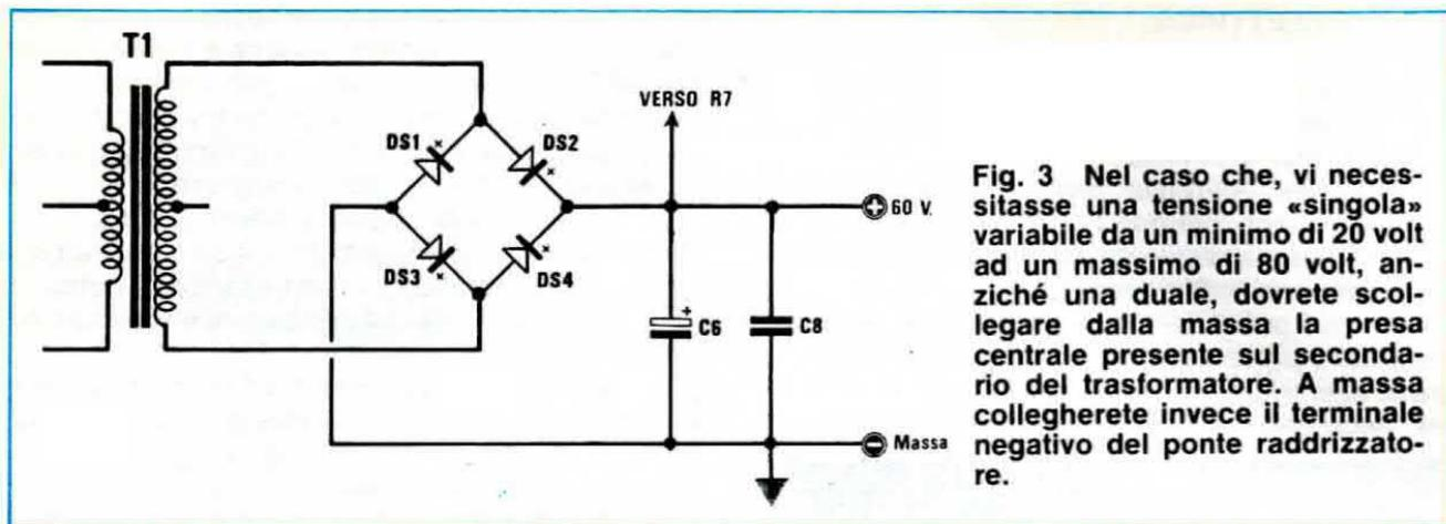
Fig. 3 Nel caso che, vi necessitasse una tensione «singola» variabile da un minimo di 20 volt ad un massimo di 80 volt, anziché una duale, dovrete scollegare dalla massa la presa centrale presente sul secondario del trasformatore. A massa collegherete invece il terminale negativo del ponte raddrizzatore.
