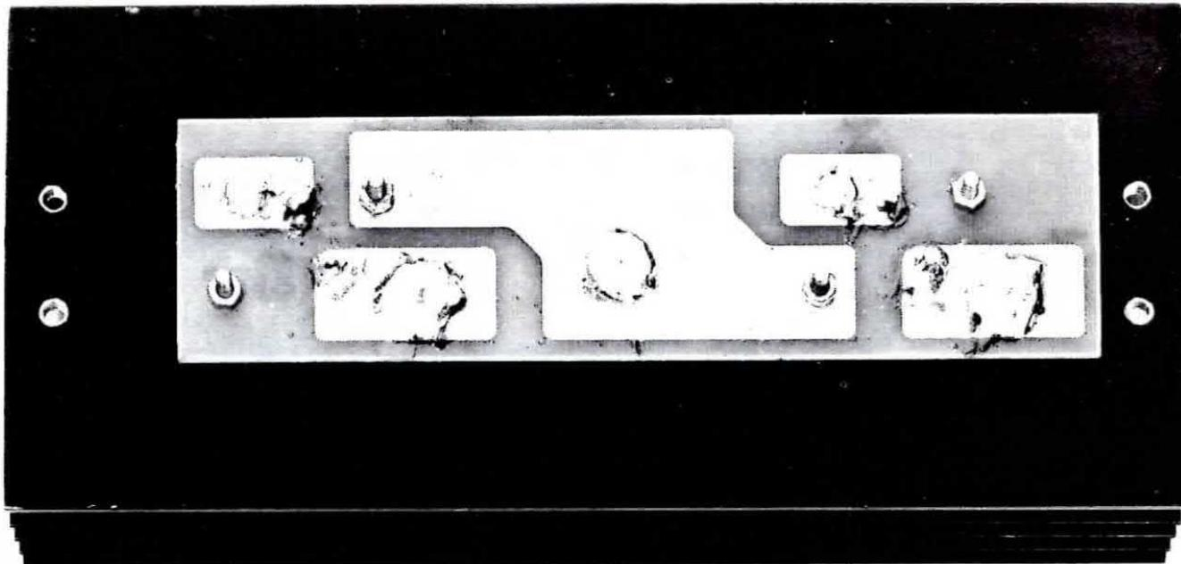
I due transistor di potenza MJ 2501 andranno montati direttamente su un'aletta di raffreddamento, e dovranno essere anche isolati con delle miche. I terminali di questi transistor li salderete sulle piste del circuito stampato LX 522/A. Per collegarli poi come vedesi in fig. 8, al primario del trasformatore T1.
