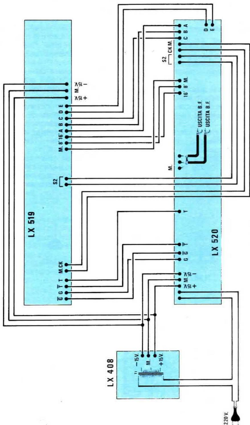
Fig. 15 I due circuiti stampati LX.519 e LX.520 dovranno essere collegati tra di loro utilizzando dei normali fili di rame isolati in plastica. In questo disegno abbiamo riportato i diversi terminali, indicati con le lettere e i numeri che saranno serigrati sui due circuiti stampati. Per alimentare questo synthesizer consigliamo di utilizzare l'alimentatore stabilizzato LX.408.
