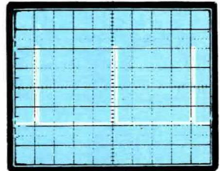
**Fig. 3** Se il tempo di chiusura risulterà pari a 1 decimo rispetto a quello di apertura, il valore medio della tensione che si potrà prelevare ai capi di tale condensatore sarà pari a 1/10 rispetto al suo valore massimo, cioè con impulsi di 20 volt si otterranno in pratica solo 2 volt.
