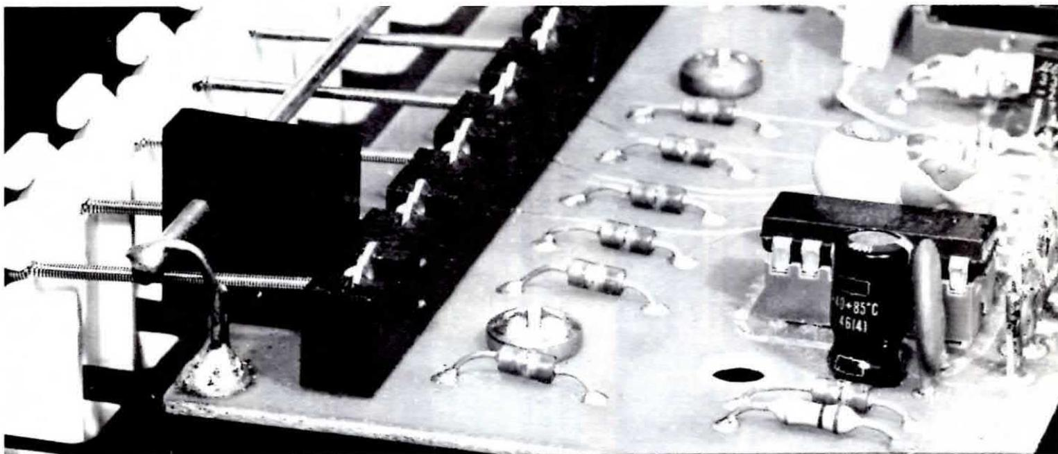
**Fig. 12** In questa foto possiamo vedere come dovranno essere stagnate le estremità delle barre di contatto sul circuito stampato, e su quale fessura del supporto verticale del tasto infilare la molla flessibile che farà capo allo scodellino infilato precedentemente entro la barra di plastica portaterminali.
