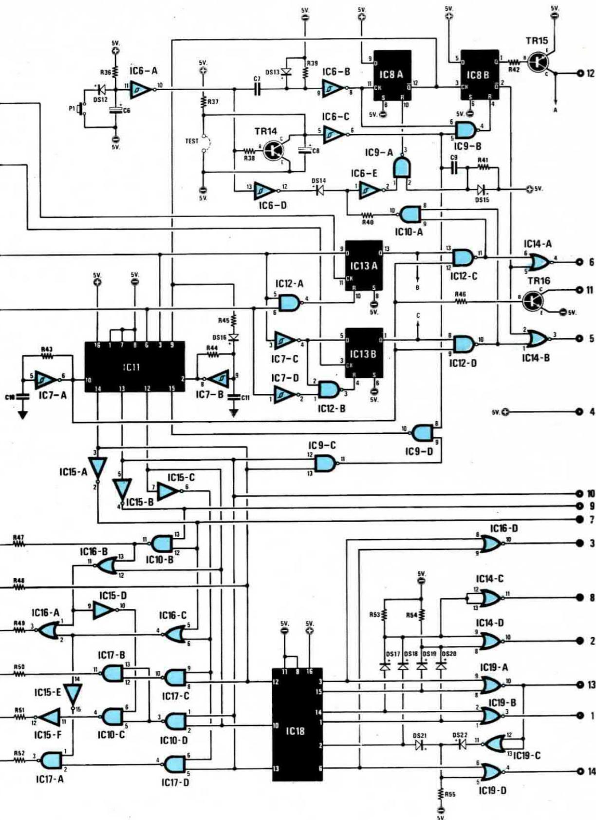
I numeri che appaiono sulla destra di tale schema andranno a collegarsi tramite una piattina a 14 fili allo schema elettrico del visualizzatore riportato in fig. 2.
