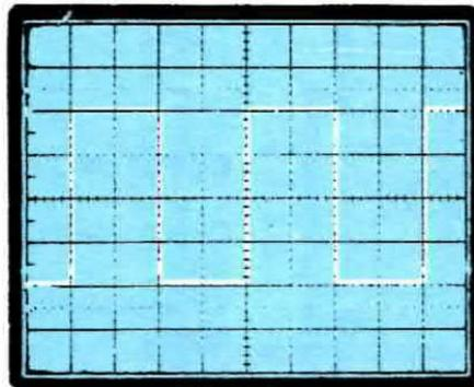
**Fig. 2** Se i tempi di chiusura risultano identici a quelli di apertura la tensione che potrà essere prelevata dal condensatore risulterà dimezzata, cioè se la tensione massima applicata nel tempo di chiusura risulta di 20 volt sul condensatore si potranno prelevare 10 volt.
