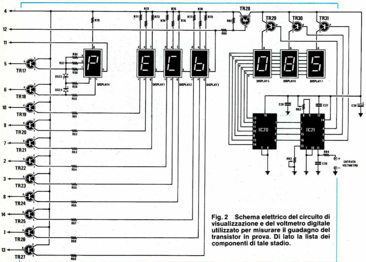
Fig. 2 Schema elettrico del circuito di visualizzazione e del voltmetro digitale utilizzato per misurare il guadagno del transistor in prova. Di lato la lista dei componenti di tale stadio.
