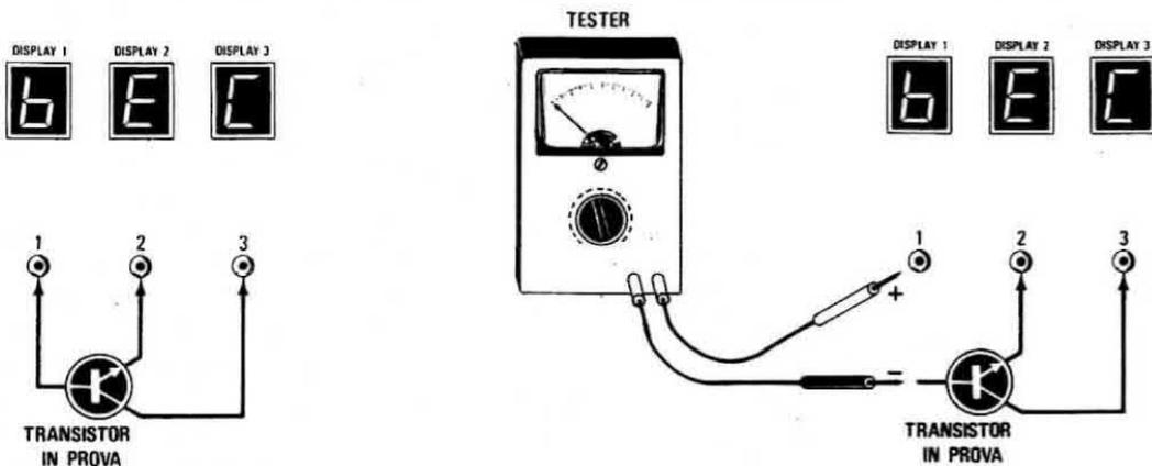
Fig. 11 Per tarare il «guadagno» dovrete applicare in serie al terminale di base del transistor, un tester posto sulla portata 50-100 microamper fondo scala, dovremo poi tarare per i transistor NPN, il trimmer R.27, e per i transistor PNP, il trimmer R.28, fino a leggere sullo strumento una corrente di 10 microamper.
