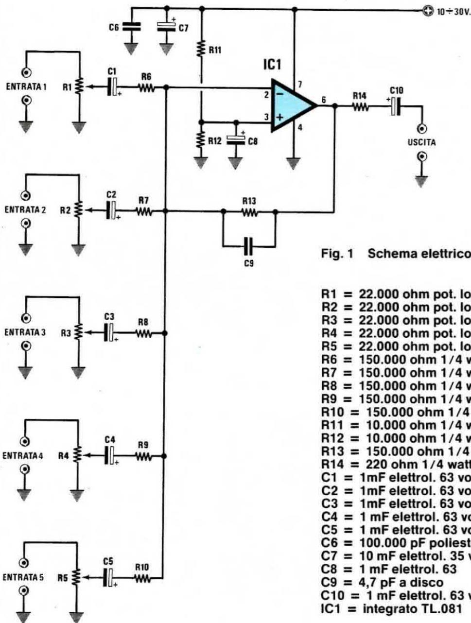
Fig. 1 Schema elettrico del mixer stereo.
