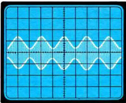
**Fig. 7** Se l'amplificatore di BF eroga una potenza minore rispetto a quella erogata dallo stadio finale AF, il segnale AF verrà modulato solo per un 30% - 40%. Come vedesi in questa foto l'ampiezza del segnale non è molto elevata.
