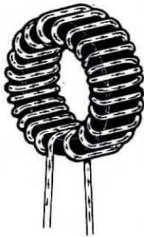
**Fig. 5** L'impedenza Z1 dovrete autocostruirvela avvolgendo intorno al nucleo in ferrite 40 spire di filo di rame smaltato del diametro di 0,7 - 0,8 mm. Ricordatevi, una volta terminato il montaggio di raschiare le due estremità di tale filo in modo da eliminare la vernice isolante.
