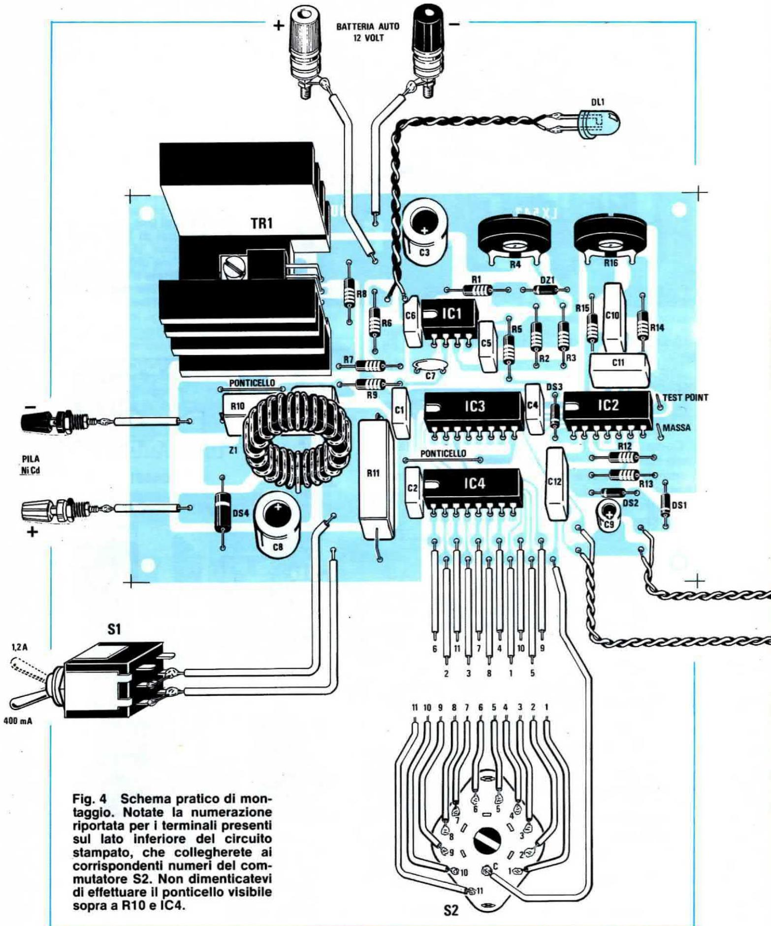
Fig. 4 Schema pratico di montaggio. Note la numerazione riportata per i terminali presenti sul lato inferiore del circuito stampato, che collegherete ai corrispondenti numeri del commutatore S2. Non dimenticatevi di effettuare il ponticello visibile sopra a R10 e IC4.
