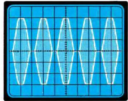
**Fig. 9** Se il segnale di BF risulta di potenza superiore a quello del segnale AF si «sovramodula» cioè l'onda sinusoidale viene troncata superiormente e al centro e in ricezione il segnale verrà captato distorto.
