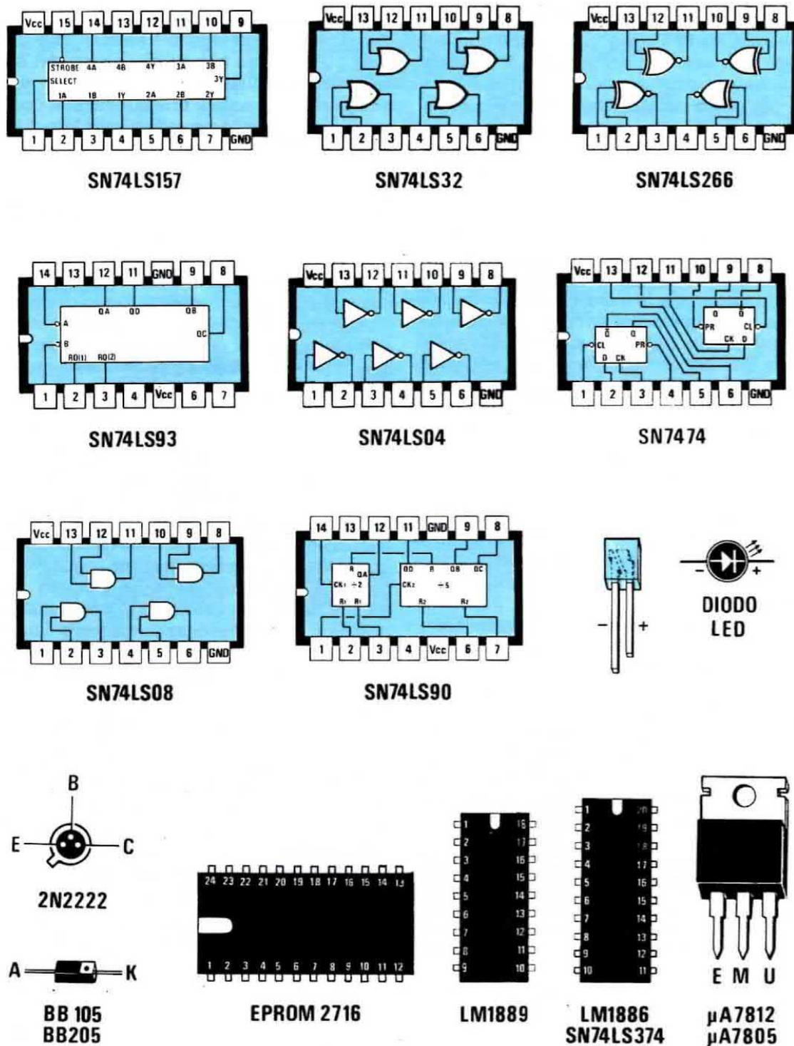
**Fig. 4** Connessioni di tutti gli integrati utilizzati in tale progetto, visti da sopra. Si noti la tacca di riferimento posta sulla destra. Per il transistor 2N2222 le connessioni sono viste da sotto, cioè dal lato dove i terminali EBC fuoriescono dal corpo. Il catodo del diodo varicap BB105 lo si riconosce dalla parte bianca del corpo, mentre quella del diodo led dal terminale più corto.
