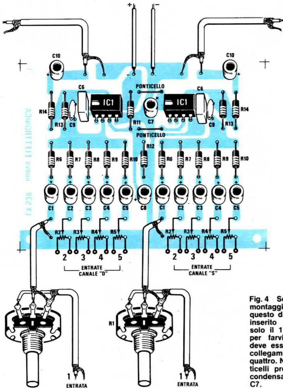
Fig. 4 Schema pratico di montaggio del mixer. In questo disegno abbiamo inserito nei due canali solo il 1° potenziometro per farvi vedere come deve essere effettuato il collegamento degli altri quattro. Notate i due ponticelli presenti vicino al condensatore elettrolitico C7.
