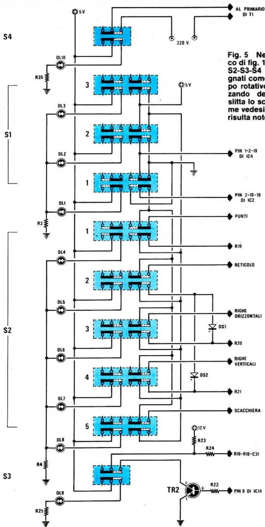
Fig. 5 Nello schema elettrico di fig. 1 i commutatori S1-S2-S3-S4 li abbiamo disegnati come se fossero del tipo rotativo, in pratica utilizzando dei commutatori a slitta lo schema elettrico come vedesi in questo disegno risulta notevolmente diverso.
