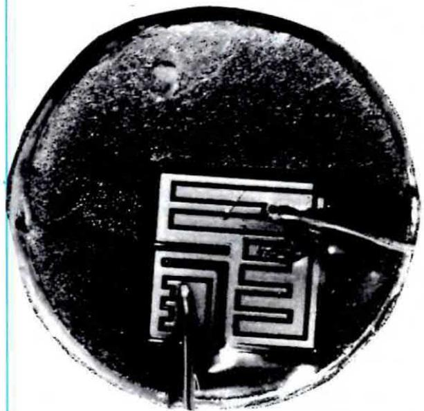
Il chip di un MJ 3001 ha un diverso disegno e una superficie quadrupla, rispetto a quella del chip di sinistra. È ovvio che inserendo in un circuito un componente diverso da quello richiesto il progetto si rifiuta di funzionare.
