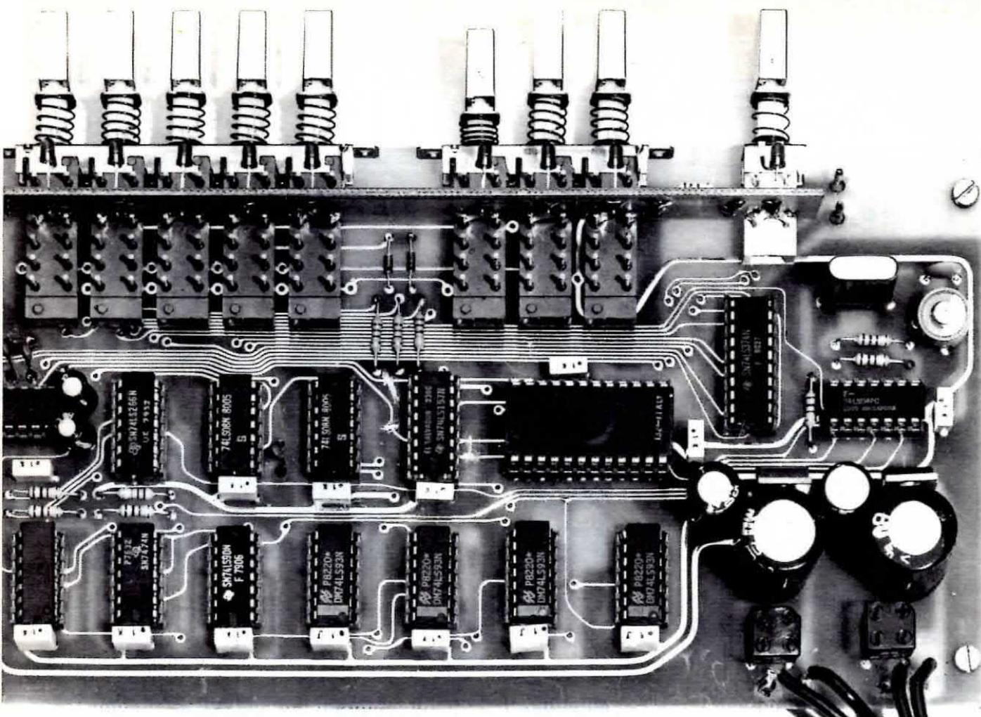
Qui sopra la foto di uno dei nostri primi prototipi di generatore di barre e colori. Si noti il circuito stampato porta-led fissato sopra i terminali dei commutatori a slitta. Nel progetto definitivo i diodi led li abbiamo sostituiti con quelli di tipo rettangolari. Di lato come si presenta la mascherina frontale del mobile. Pigiando uno dei 3 pulsanti del gruppo di destra e uno dei 5 posti a sinistra potremo ricavare le figure e i colori riportati sopra a tali commutatori.
