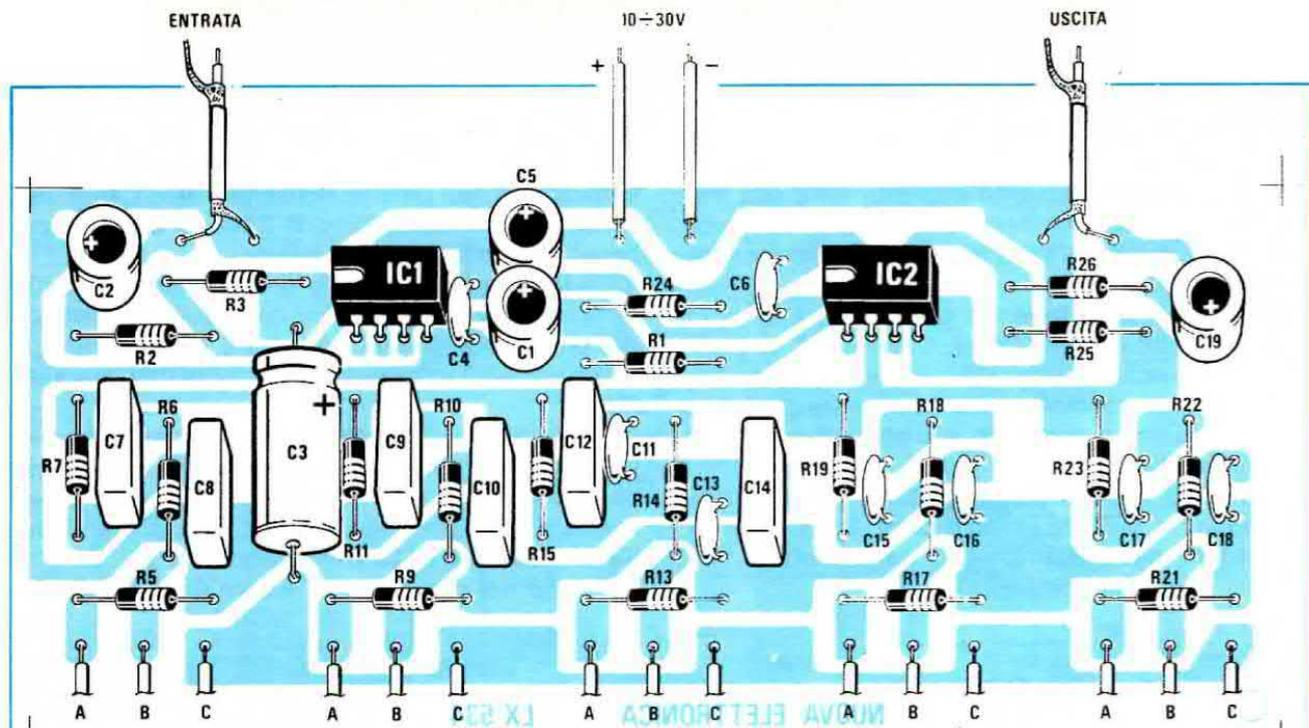
Fig. 2 Schema pratico di montaggio dell'equalizzatore. In basso sul circuito stampato sono presenti i terminali per i collegamenti dei cinque potenziometri (leggi articolo).
