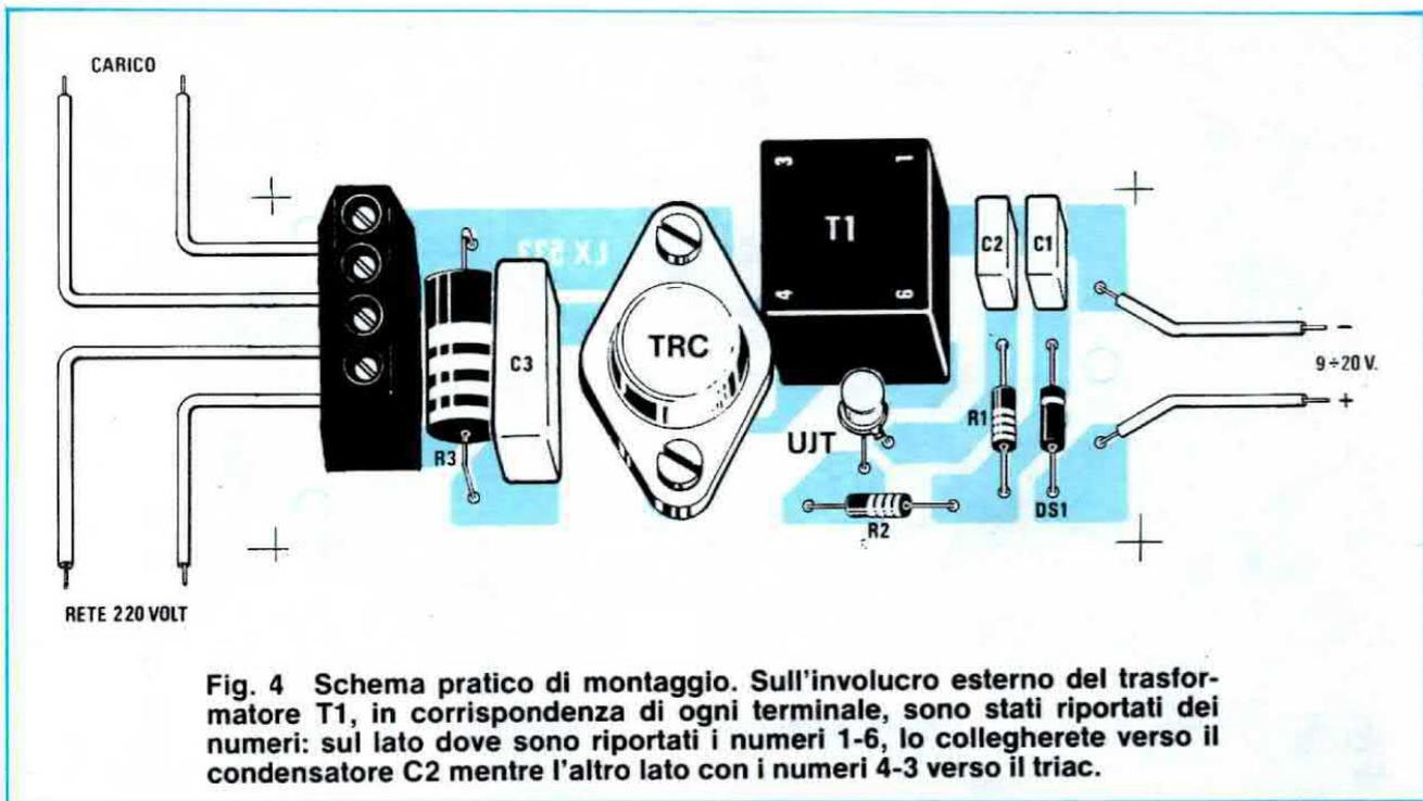
**Fig. 4 Schema pratico di montaggio. Sull'involucro esterno del trasformatore T1, in corrispondenza di ogni terminale, sono stati riportati dei numeri: sul lato dove sono riportati i numeri 1-6, lo collegherete verso il condensatore C2 mentre l'altro lato con i numeri 4-3 verso il triac.**
