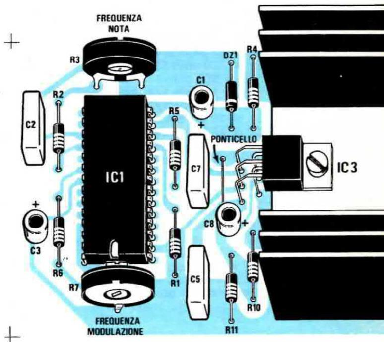
figurazione a ponte (vedi IC2 - IC3) siamo riusciti a raggiungere una potenza di circa 30 watt con un carico di 4 ohm, mentre, con un carico di 8 ohm la potenza raggiunta è di 15 watt.
