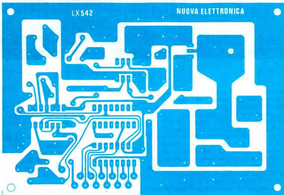
Fig. 2 Qui sopra abbiamo riportato nelle sue dimensioni naturali il circuito stampato siglato LX 542 che richiederete per realizzare il carica-pila.
