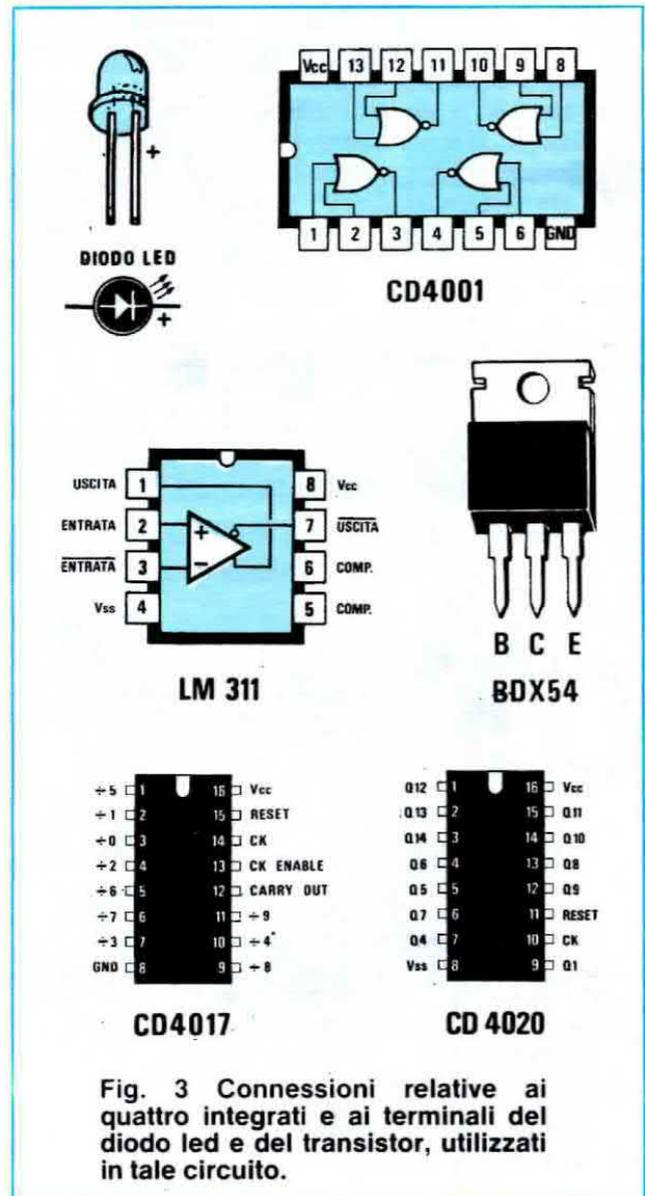
Fig. 3 Connessioni relative ai quattro integrati e ai terminali del diodo led e del transistor, utilizzati in tale circuito.
