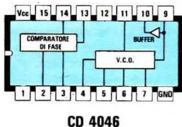
**Fig. 4** L'integrato che permette di ottenere un così semplice oscillatore di BF-MF è il CD.4046, in questo disegno è possibile vederne le connessioni dei terminali visti da sopra.
