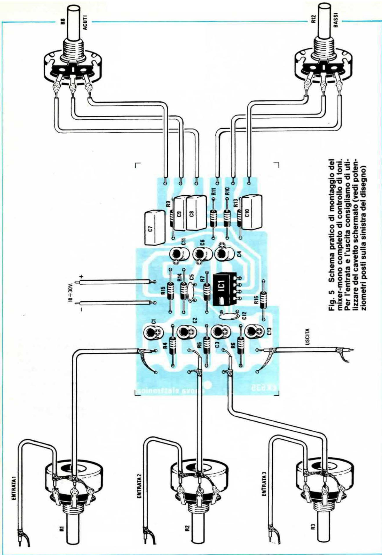
Fig. 5 Schema pratico di montaggio del mixer-mono completo di controllo di toni. Per l'entrata e l'uscita consigliamo di utilizzare del cavetto schermato (vedi potenziometri posti sulla sinistra del disegno)
