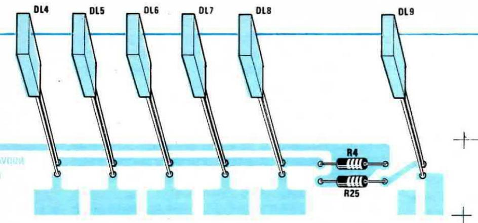
**Fig. 6** Schema pratico di montaggio dei led sul circuito stampato LX.539/A.
