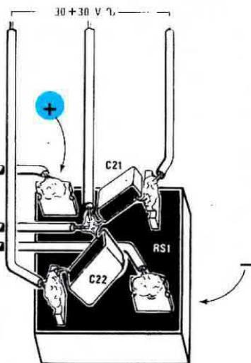
**Fig. 5** Per ridurre un leggero ronzio di alternata, collegate il filo di massa (visibile a destra) sulla morsetteria di sinistra dalla quale parte il filo di massa per l'altro canale.
