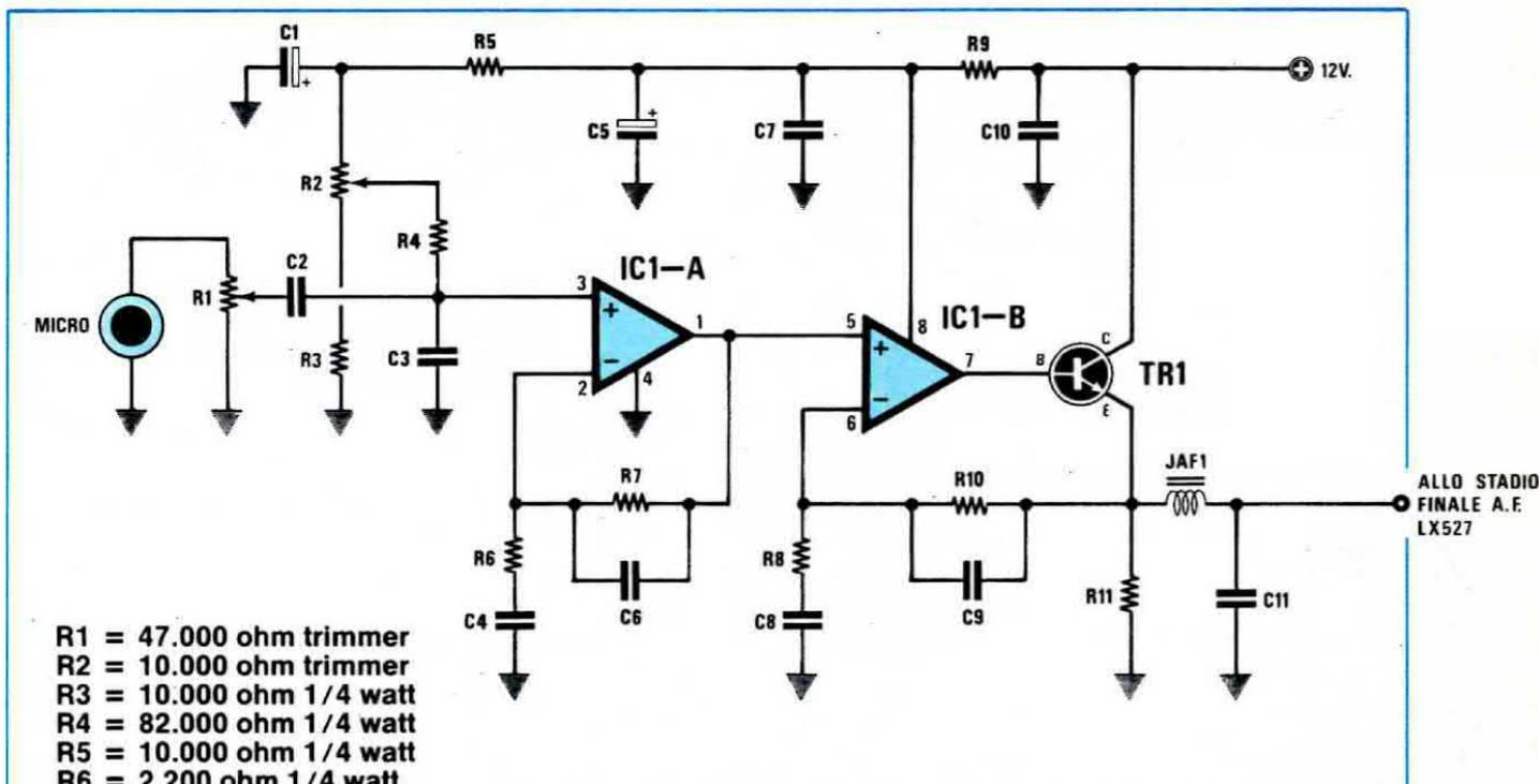
Fig. 12 Schema elettrico del modulatore
