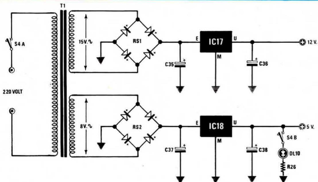
**Fig. 2** Schema elettrico dello stadio alimentatore. Tale stadio come vedesi nello schema pratico di fig. 3 risulta già riportato sul circuito stampato LX.539. Per i valori dei componenti vedere la lista riportata qui sotto.
