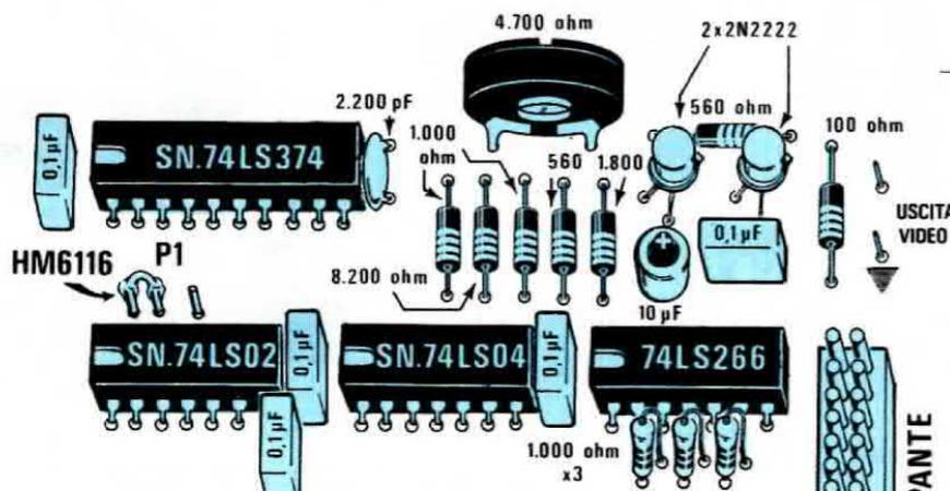
noterete, in questa scheda, se vengono utilizzate RAM M.5516 dovrete cortocircuitare il ponticello P1 come riportato in fig. 2 utilizzando invece delle HM.6116 (che dovrebbero risultare equivalenti) dovrete cortocircuitare tale ponticello come riportato in fig. 3.
