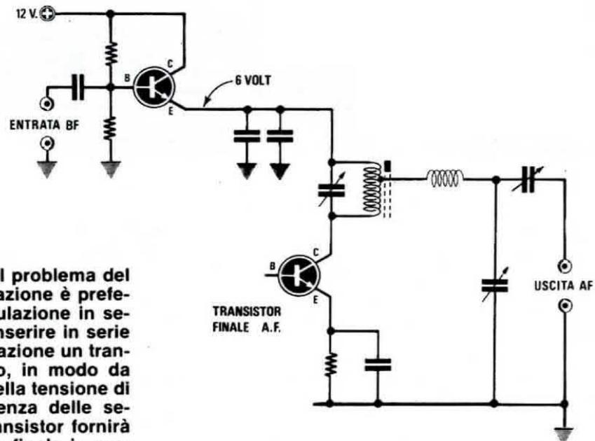
Fig. 11 Per eliminare il problema del trasformatore di modulazione è preferibile adottare la «modulazione in serie» che consiste nell'inserire in serie alla tensione di alimentazione un transistor di BF polarizzato, in modo da fornire in uscita metà della tensione di alimentazione. In presenza delle semionde positive tale transistor fornirà più tensione allo stadio finale, in presenza di quelle negative minor tensione e così facendo, il segnale AF risulterà modulato.
