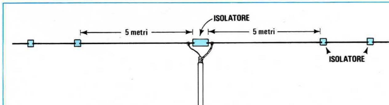
**Fig. 1** Se non disponete di un'antenna ground-plane per i 27 MHz. con due spezzoni di filo di rame da 1 a 2 mm. potrete costruire questo semplice dipolo. Per la discesa potrete utilizzare del normale cavo coassiale per TV che come saprete dispone di un'impedenza di 75 ohm.
