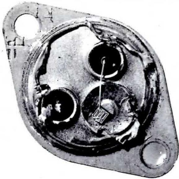
Qui sopra, la foto del darlington montato sull'alimentatore LX 343 inviatoci dall'Ing. A.F. di Terracina. Controllando con un tracciacurve tale darlington, acquistato dall'Ingegnere presso un negoziante di fiducia, abbiamo immediatamente constatato che risultava un comune transistor, aprendolo infatti, ne abbiamo avuto la conferma.
