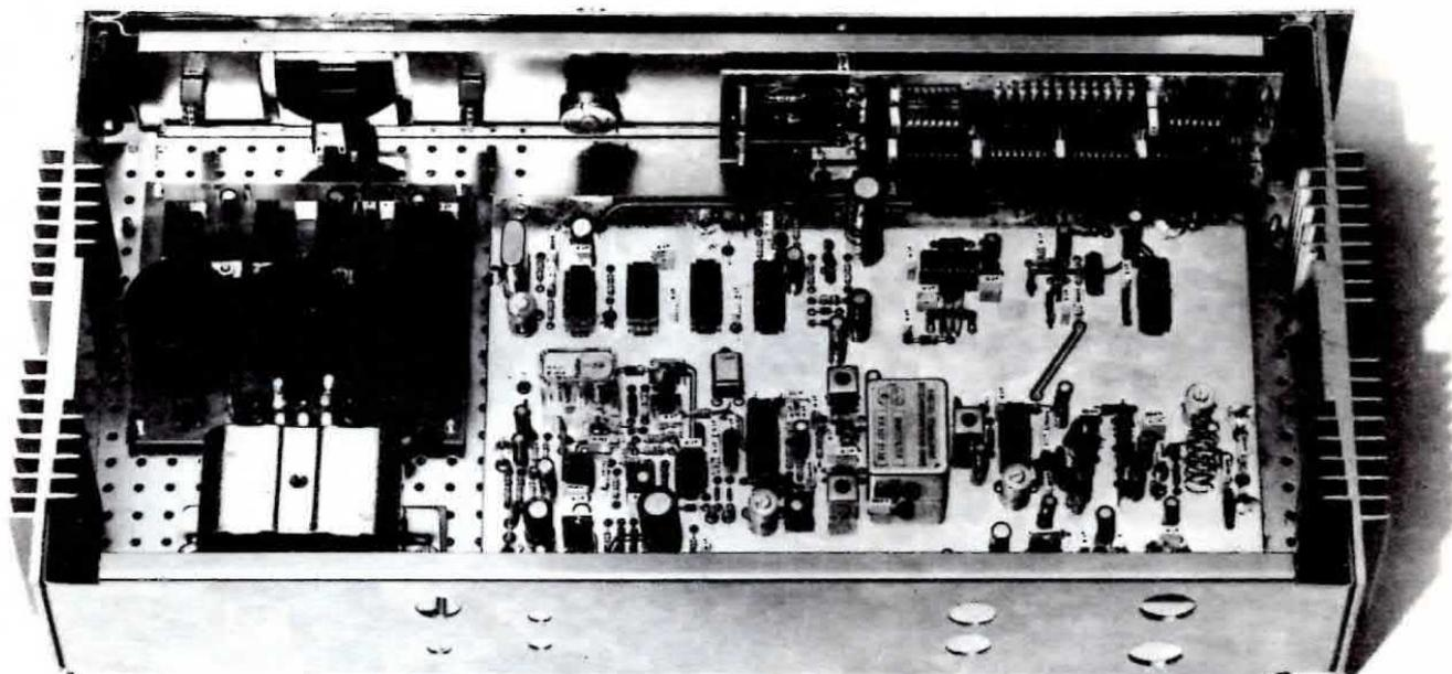
**Fig. 7** Come vedesi in questa foto il circuito stampato della sintonia digitalizzata dovrà essere fissato sul contropannello del mobile, a sinistra fisserete lo strumento S-Meter utilizzando una fascetta e sul piano, i circuiti stampati del ricevitore e dell'alimentatore tenendoli sollevati da questo di 3-4 millimetri per evitare di cortocircuitare le piste inferiori.
