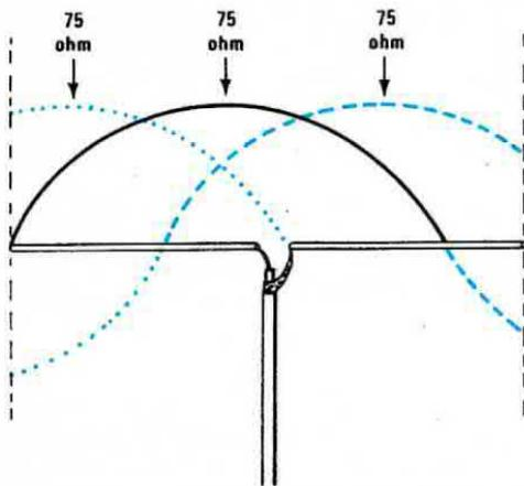
**Fig. 19** Se l'antenna risultasse più lunga del richiesto, la semionda negativa utilizzerebbe per iniziare il suo ciclo la lunghezza eccedente e così facendo il VENTRE di corrente si sposterebbe ad ogni semiciclo verso destra o a sinistra quindi al centro l'impedenza non risulterebbe mai costante.
