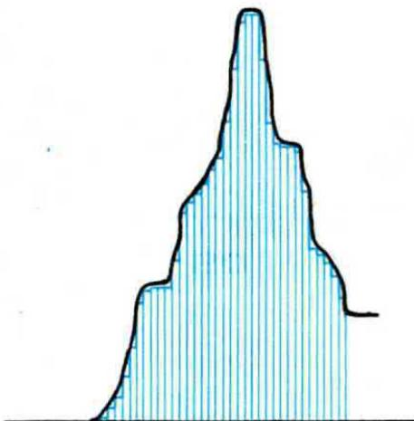
**Fig. 14** Un convertitore analogico digitale provvederà a scomporre tale segnale (vedi particolare A di fig. 13) in tanti livelli digitali (1.200 livelli per linea) per poterne ricavare tutte le tonalità di colore cioè bianco-grigio leggero, grigio medio, grigio medio forte, ecc. fino al nero.
