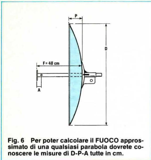
**Fig. 6** Per poter calcolare il FUOCO approssimato di una qualsiasi parabola dovrete conoscere le misure di D-P-A tutte in cm.
