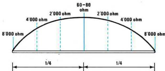
**Fig. 6** Con un'antenna lunga META lunghezza d'onda sul VENTRE di corrente sarà presente un'impedenza compresa tra i 60 e gli 80 ohm, mentre sui NODI di corrente un'impedenza di circa 8.000 ohm.
