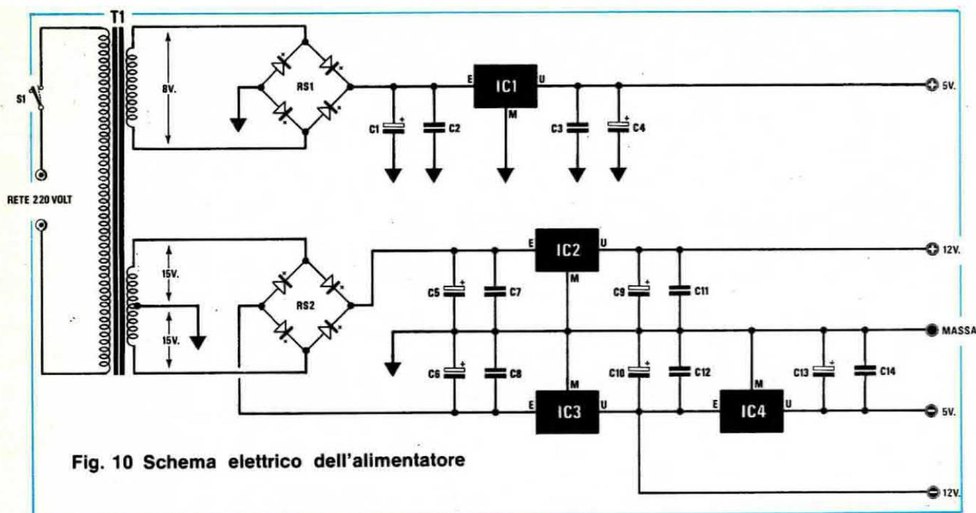
Fig. 10 Schema elettrico dell'alimentatore
