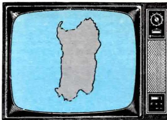
**Fig. 26** Sempre con un ingrandimento X4 la Sardegna vi occuperà tutto lo schermo del video. Come spiegato nell'articolo le immagini di ogni settore interessato scorreranno lentamente sullo schermo del TV dall'alto verso il basso, se vi interessa una determinata zona quando questa risulterà centrata sul televisore la potrete bloccarla con l'interruttore di Stop presente sul video-converter.
