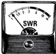
**Fig. 15** Lo strumento applicato sui misuratori di onde stazionarie indica il rapporto esistente tra l'onda diretta e quella riflessa.
