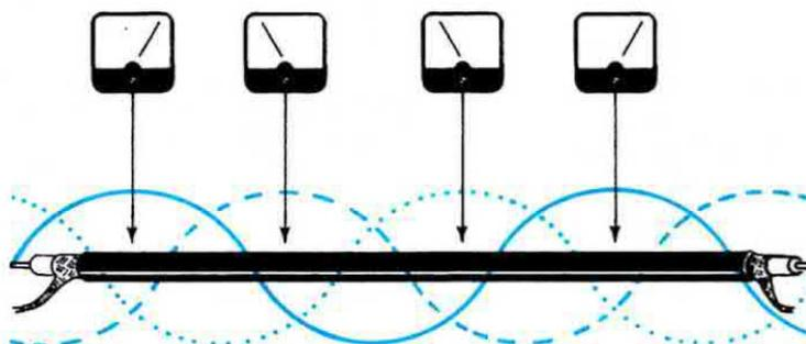
**Fig. 21** Se l'impedenza dell'antenna (vedi fig. 19 e 20) nel punto di giunzione con il cavo coassiale non risulta costante, avremo delle **ONDE STAZIONARIE** e questo significa che lungo il cavo coassiale non ritroveremo come per la fig. 17 una tensione fissa, ma tensioni variabili. Nei punti dove si formano dei **NODI** di corrente si possono rilevare anche tensioni di circa 800-1.000 volt che oltre a far surriscaldare il cavo potrebbero anche perforarlo.
