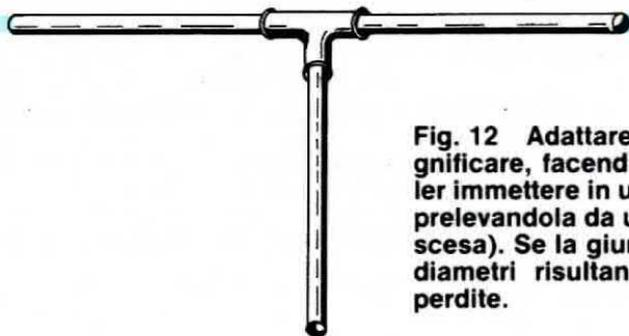
**Fig. 12** Adattare un'impedenza potrebbe significare, facendo un'analogia idraulica, voler immettere in un tubo (antenna) dell'acqua prelevandola da un secondo tubo (cavo di discesa). Se la giunzione è perfetta, cioè i due diametri risultano identici non si avranno perdite.
