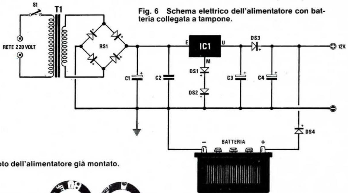
Fig. 6 Schema elettrico dell'alimentatore con batteria collegata a tampone.
