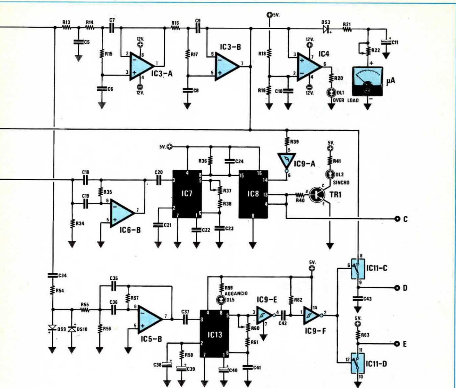
Fig. 2 Circuito elettrico dello stadio d'ingresso. Per la lista componenti vedere a pag. 124.
