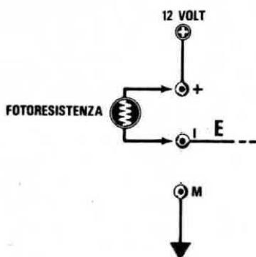
Fig. 4 Sull'ingresso E potrà essere collegata come vedesi in figura una fotoresistenza, oppure un contatto normalmente aperto collegato tra i terminali + ed E.
