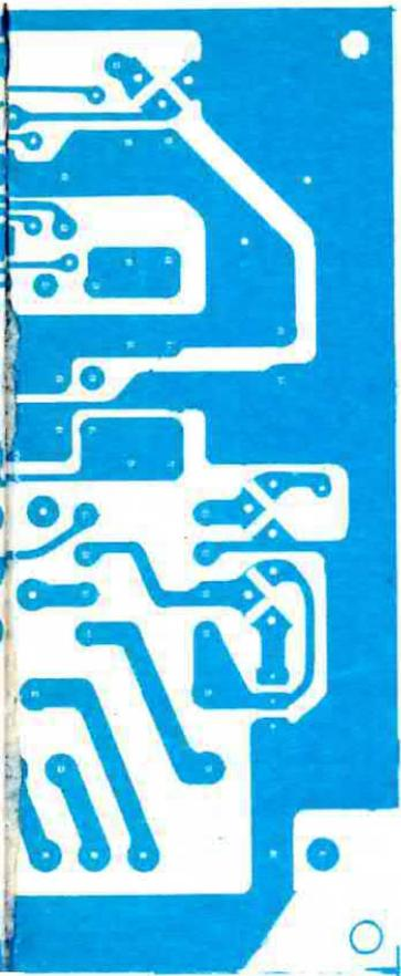
**Fig. 9** Disegno a grandezza naturale di una sola facciata del circuito stampato LX. 543. Questo circuito è dotato di fori metallizzati, eviterete quindi di effettuare i collegamenti tra piste inferiori e superiori.
