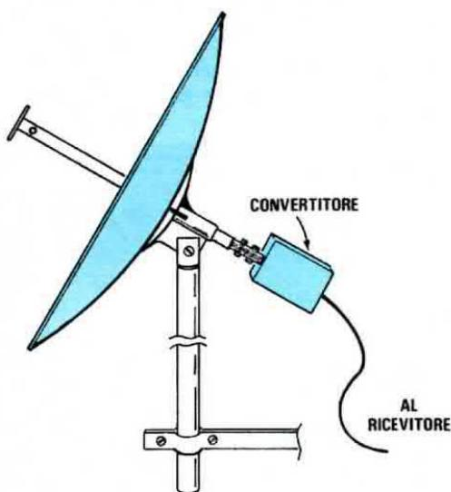
**Fig. 5** Per il fissaggio al palo TV, conviene utilizzare 2 staffe anzichè una sola.
