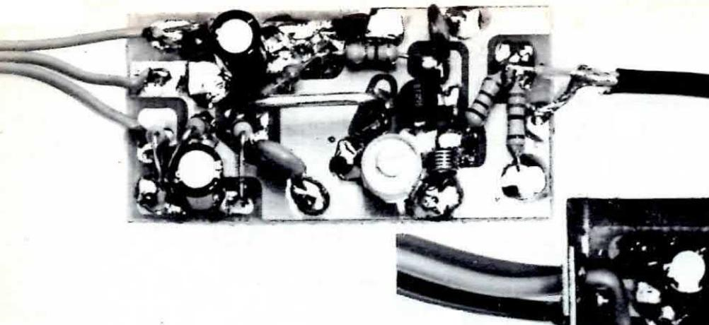
Fig. 6 Foto del modulatore video. Tutti i componenti andranno stagnati direttamente sul lato rame. Si noti la bobina L1 a U vedi fig. 8.
