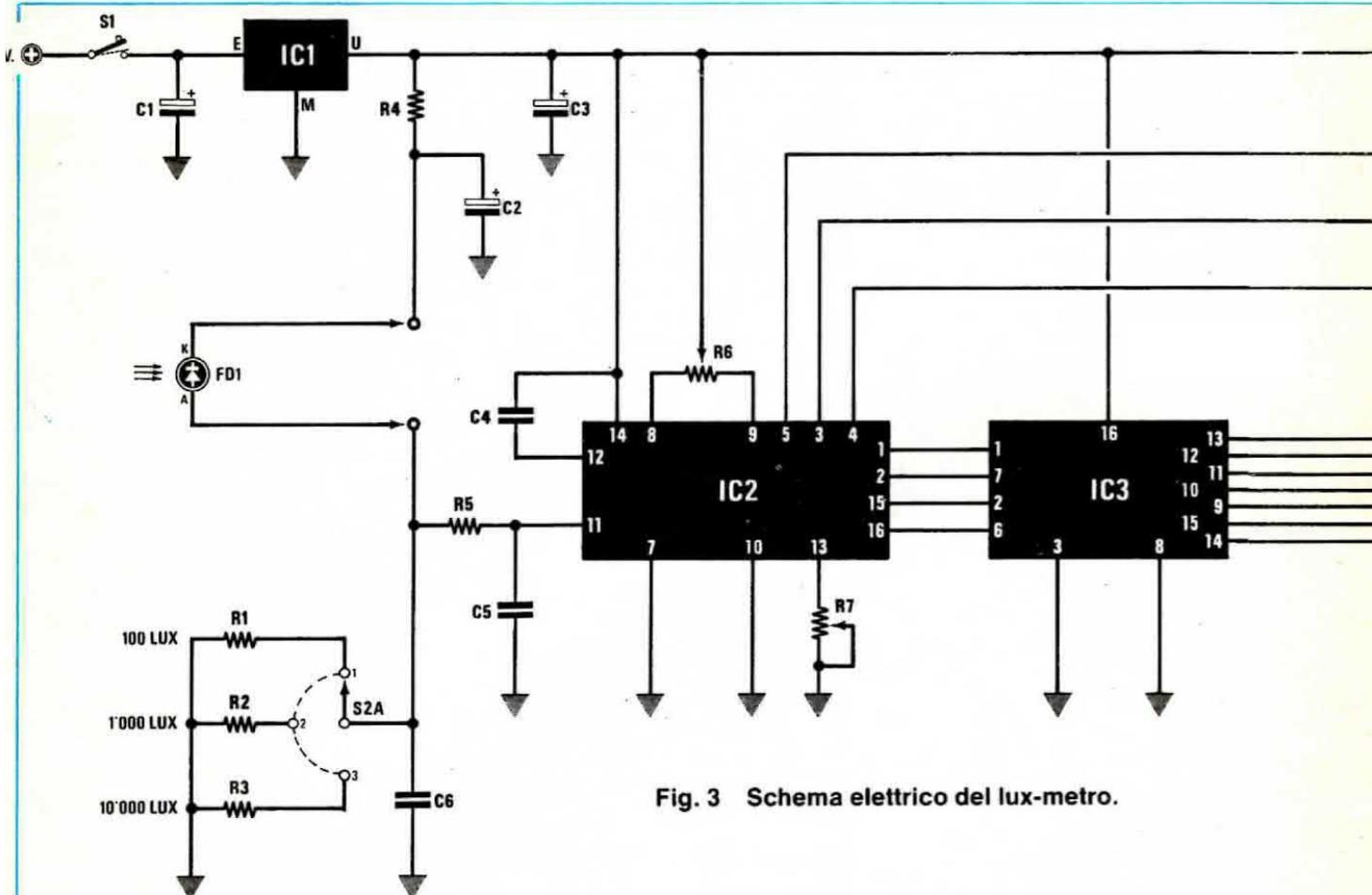
Fig. 3 Schema elettrico del luxmetro.
