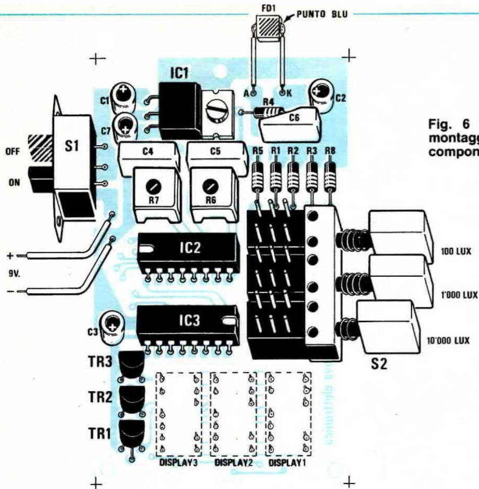
Fig. 6 Schema pratico di montaggio visto dal lato dei componenti.
