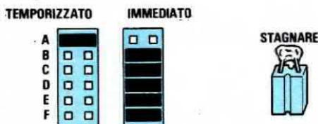
Fig. 11 Nei due connettori maschi presenti sul circuito stampato innesterete le piccole spinette femmina dopo averne cortocircuitato superiormente i due terminali con una goccia di stagno come visibile nel disegno qui riportato.
