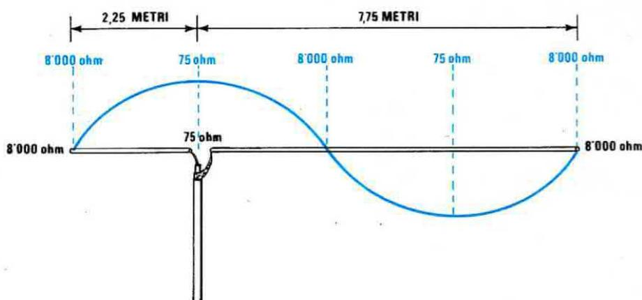
**Fig. 23** Volendo lasciare l'antenna lunga un'ONDA INTERA per poterla accoppiare ad un cavo coassiale di 75 ohm, dovremo necessariamente collegarla in un VENTRE di corrente, cioè a 1/4 d'onda rispetto ad una delle due estremità. Così facendo l'antenna risulta perfettamente adattata al cavo coassiale e non avremo più alcuna perdita per disadattamento d'impedenza.
