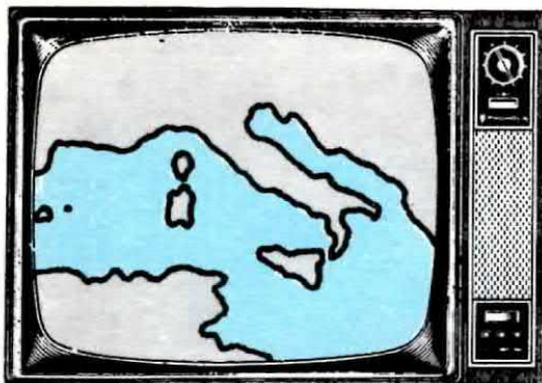
**Fig. 23** Qualsiasi foto trasmessa dal satellite la possiamo ingrandire -X2 -X4. Con un ingrandimento X4 questa immagine viene divisa in quattro parti e ognuna di queste ingrandita per la massima larghezza dello schermo video. Negli ingrandimenti X4 si ottiene la massima definizione perché tutti i PUNTI trasmessi dal satellite vengono visualizzati sullo schermo TV.
