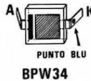
Fig. 2 Per individuare il Katodo del diodo dovrebbe essere presente su tale terminale un piccolissimo punto di vernice «blu». Nel caso che tale punto di riferimento risultasse inesistente si potrà sempre individuare il terminale Anodo poiché da tale lato all'interno del fotodiode è visibile una riga «nera».
