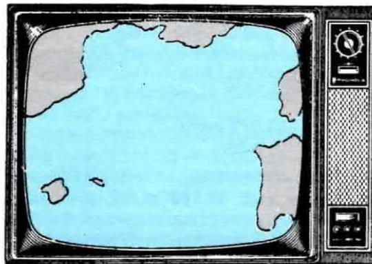
**Fig. 18** Ruotando il commutatore binario sul n. 3 il lato sinistro dell'immagine riportata in fig. 17 verrà ingrandito di 2 volte. La definizione dell'immagine con un ingrandimento X2 ne risulterà migliorata in quanto il microcomputer, come spiegato nell'articolo, condensa in un solo punto i livelli di colore di 2 soli punti.
