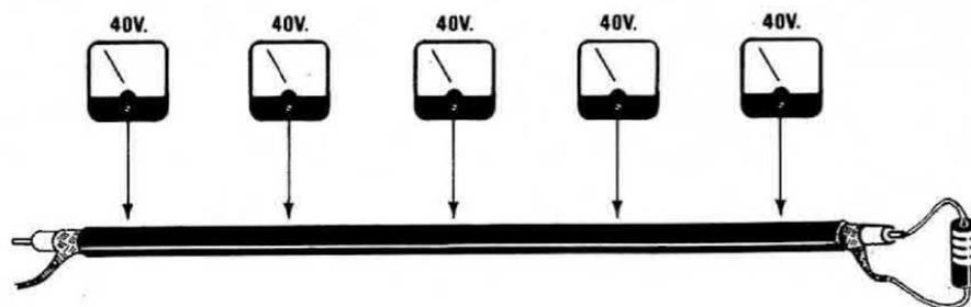
**Fig. 17** Quando l'impedenza applicata sull'estremità del cavo coassiale (antenna o sonda di carico) risulta analoga a quella del cavo coassiale, anche se questo risultasse lungo 100 o più metri si ritroverebbe in qualsiasi punto la stessa identica tensione rilevata con la sonda di carico direttamente sull'uscita del trasmettitore.
