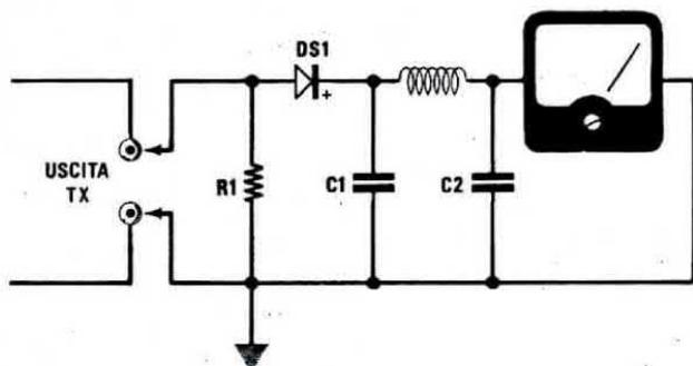
**Fig. 16** Una sonda di carico, come spiegato sulle riviste n. 81 e n. 84/85 è composta semplicemente da una resistenza ANTIINDUTTIVA (vedi R1), un diodo rivelatore, un'impedenza JAF1 e due condensatori di fuga. Sul tester si può rilevare una tensione e da questa si può ricavare la potenza in watt del trasmettitore.
