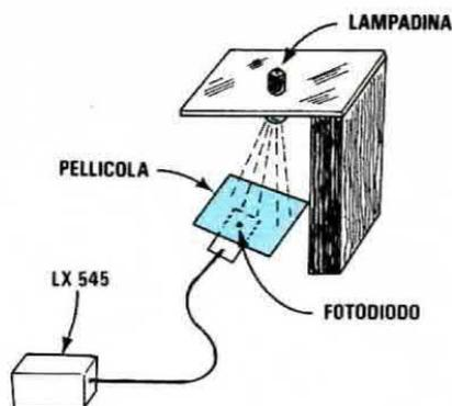
**Fig. 11** Con un supporto provvisto di una lampadina a 4,5-12 volt si potrà controllare la densità di una pellicola fotografica
