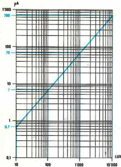
Fig. 1 Per la realizzazione di questo Luxmetro abbiamo scelto il fotodiode BPW 34 perché oltre che risultare particolarmente sensibile alle basse luminosità risulta molto lineare. Come vedesi in questo grafico con 10 lux il diodo lascerà scorrere 0,7 microamper, con 100 lux, 7 microamper, con 1.000 lux 70 microamper e con 10.000 lux 700 microamper.
