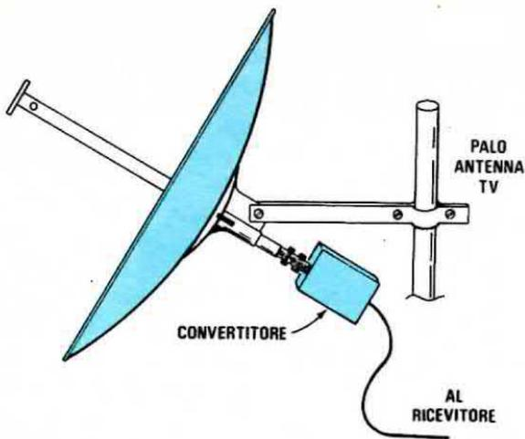
**Fig. 3** La parabola come vedesi in questo disegno potrete facilmente fissarla ad un palo per TV.
