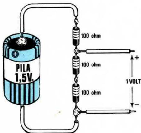
**Fig. 12** Realizzando questo partitore resistivo con tre resistenze da 100 ohm ed una pila da 1,5 volt si otterrà la tensione di 1 volt necessario, per la taratura del lux-metro.
