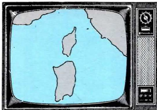
**Fig. 19** Ruotando il commutatore binario sul n. 2 verrà ingrandita la parte centrale dell'immagine, e questo ci permetterà di inquadrare la Sardegna, la Corsica e salendo anche tutta la Liguria, la Svizzera e la Germania occidentale. Avendo a disposizione 256 livelli di grigio potremo con i comandi «colore» accentuare o attenuare la nebbia e la foschia.
