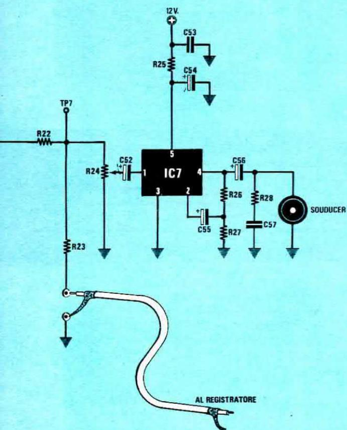
**Fig. 3A** Il segnale di BF prelevato dalla resistenza R.23 dovrà essere collegato, tramite un cavetto schermato, ad un qualsiasi registratore, oppure al Video-Converter presentato su questo stesso numero.
