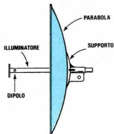
**Fig. 2** Per completare questa antenna, oltre alla parabola, è necessario il supporto posteriore in fusione di alluminio e l'illuminatore visibile in fig. 1.
