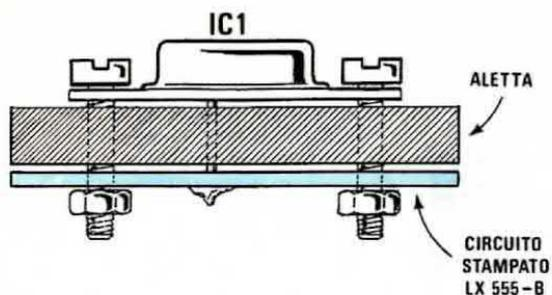
Fig. 11 L'integrato stabilizzatore IC1 lo fisseremo sull'aletta laterale sinistra del mobile. Sul lato interno, fisseremo con le viti dell'integrato, il circuito stampato LX.555/B.
