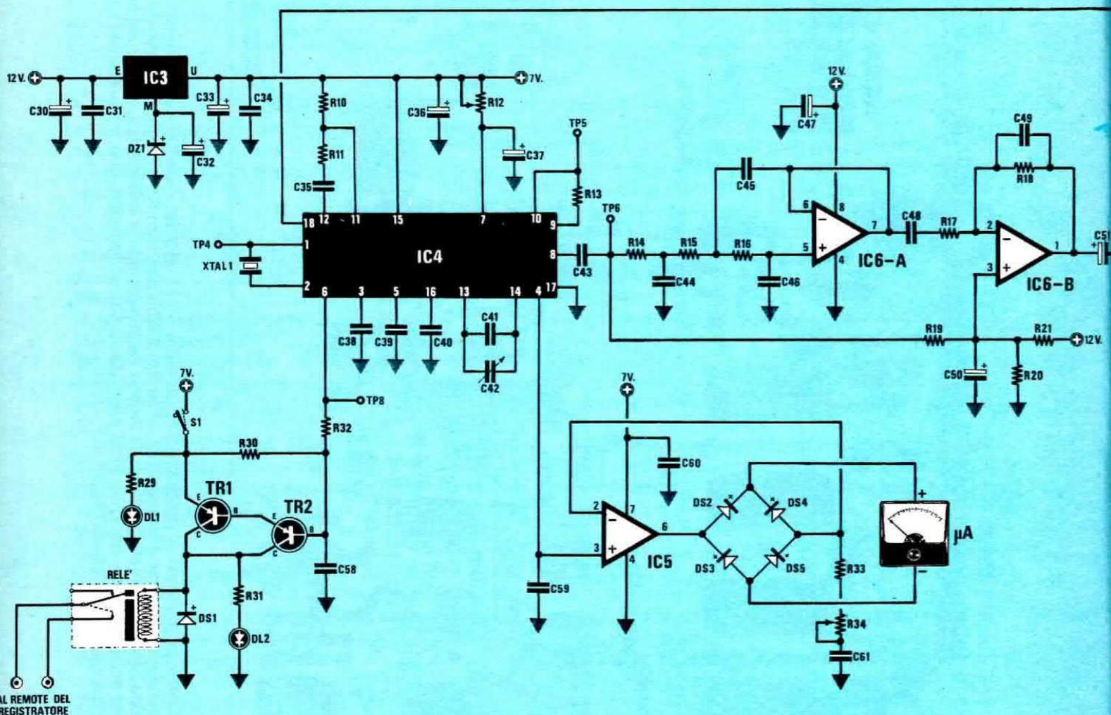
Fig. 3 Schema elettrico del solo stadio ricevente, in fig. 5 abbiamo riportato invece lo stadio dell'oscillatore locale e della sintonia digitalizzata che dovrà essere collegata al piedino 13 di IC2 (vedi «al VFO»). La lista componenti la troverete a pag. 91. Tutti i terminali indicati con le scritte TP sono dei «test point» utili in fase di taratura.
