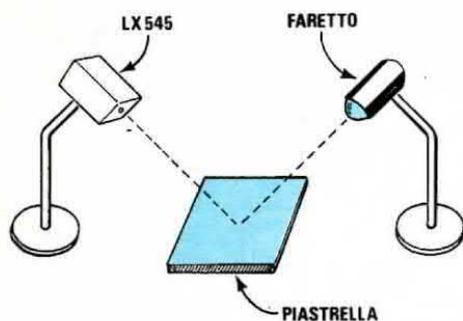
**Fig. 10** Il lux-metro potrà essere utilizzato anche per controllare una differenza di colore misurandone la luce riflessa.
