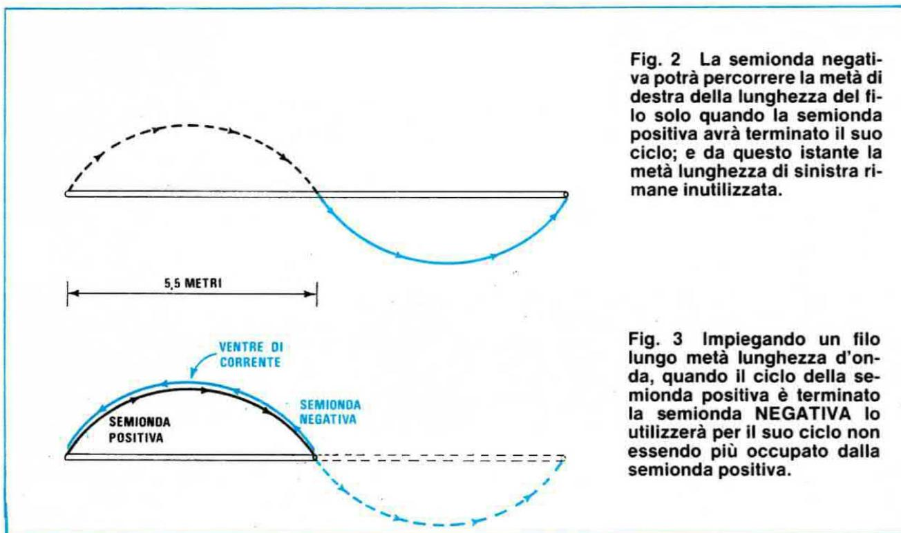
Fig. 2 La semionda negativa potrà percorrere la metà di lunghezza del filo solo quando la semionda positiva avrà terminato il suo ciclo; e da questo istante la metà lunghezza di sinistra rimane inutilizzata.
