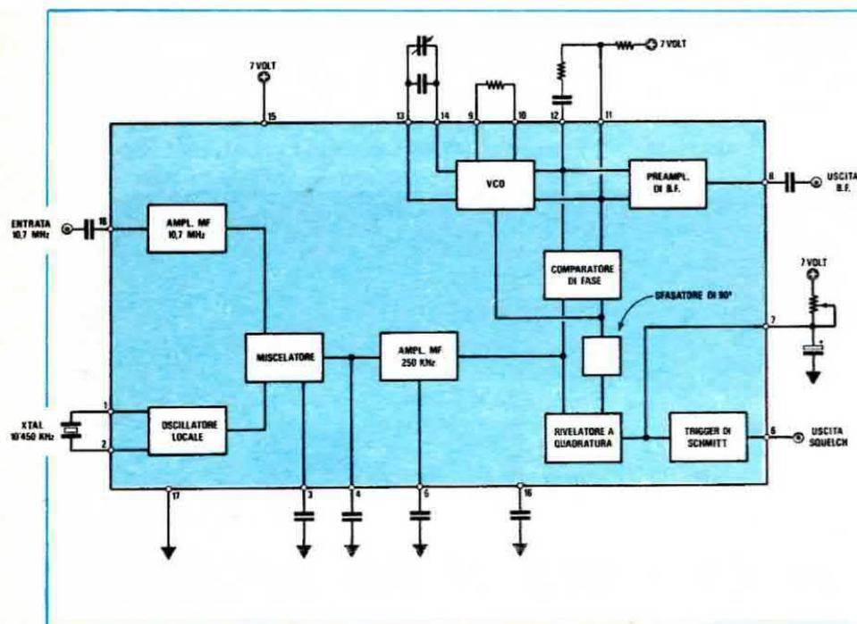
Fig. 1 L'integrato SL.6601 utilizzato in questo ricevitore, dopo aver convertito il segnale di MF a 10,7 MHz in un secondo valore di MF a 250 KHz, lo demodula in frequenza con un rivelatore sincrono a PLL.
