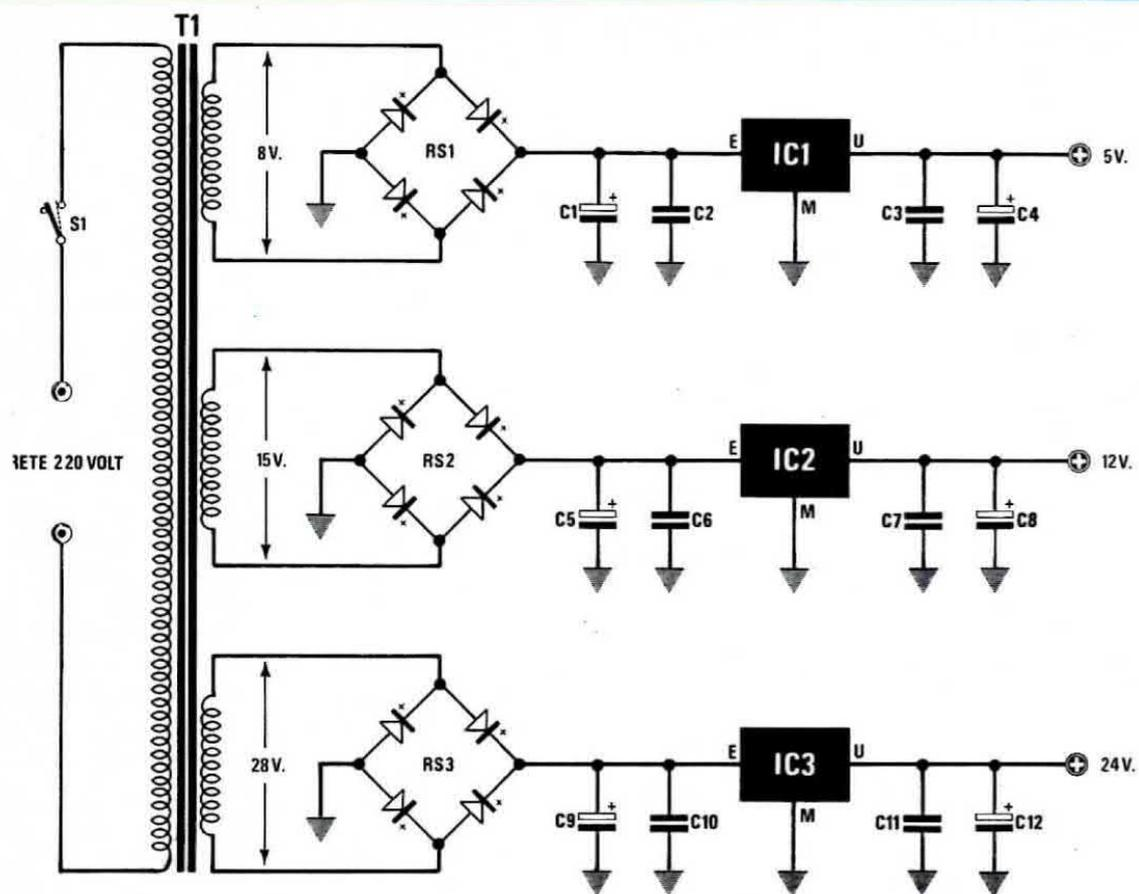
**Fig. 8** Schema elettrico dell'alimentatore e foto del circuito montato. Si notino i tre integrati stabilizzatori montati sulle alette di raffreddamento, solo IC1 che eroga i 5 volt deve essere montato sull'aletta più grande. Controllate che i terminali degli integrati non risultino in corto con l'aletta.
