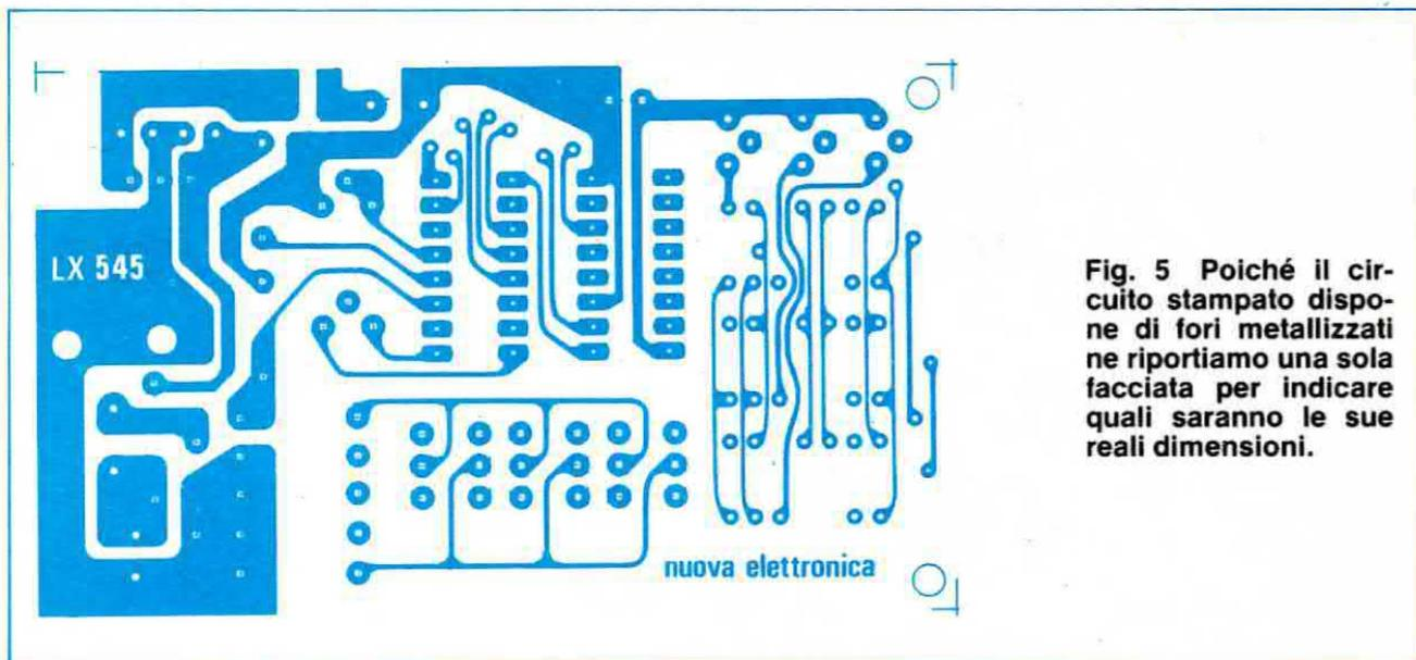
Fig. 5 Poiché il circuito stampato dispone di fori metallizzati ne riportiamo una sola facciata per indicare quali saranno le sue reali dimensioni.
