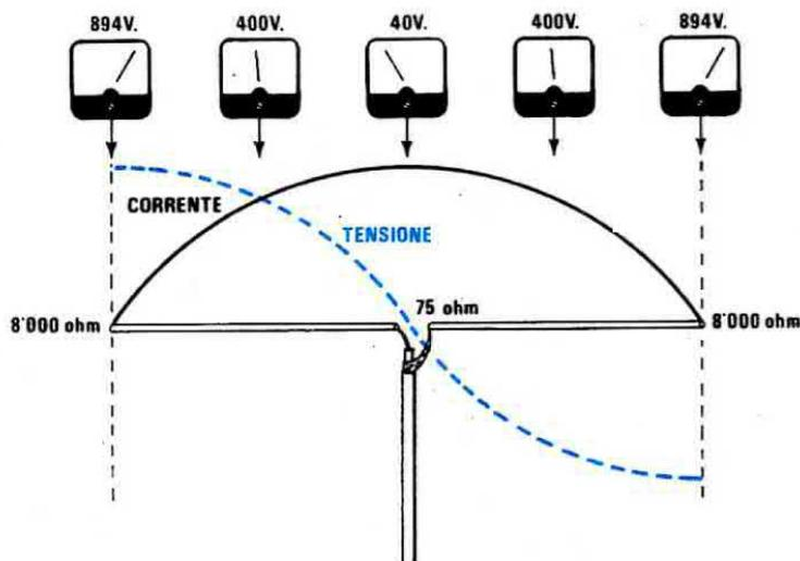
**Fig. 18** Sul ventre di corrente di un dipolo perfettamente adatto ritroveremo sempre la stessa identica tensione ed un identico assorbimento di corrente. Più ci si allontana dal ventre di corrente verso i nodi, posti alle estremità, la tensione proporzionalmente aumenta, aumentando così anche il valore dell'impedenza caratteristica.
