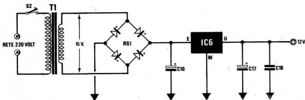
Fig. 2 Schema elettrico dello stadio alimentatore. Per i valori dei componenti vedere l'elenco riportato in fig. 1.
