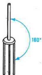
Fig. 9 Ripiegando i bracci a 180° in modo da ottenere un dipolo verticale l'impedenza caratteristica assume un valore compreso tra i 70 e gli 80 ohm.
