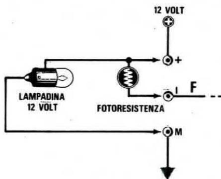
Fig. 5 Collegando una fotoresistenza sull'ingresso F questa dovrà essere completata da una lampadina in modo che il fascio di luce ne colpisca la superficie.
