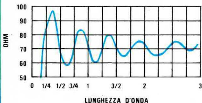
Fig. 7 L'impedenza caratteristica sul ventre di corrente di un dipolo orizzontale; varia in funzione all'altezza. Inoltre, contribuiscono a modificare l'impedenza anche gli isolatori posti alle estremità, alberi, tubazioni idrauliche e grondaie poste nelle immediate vicinanze dell'antenna.
