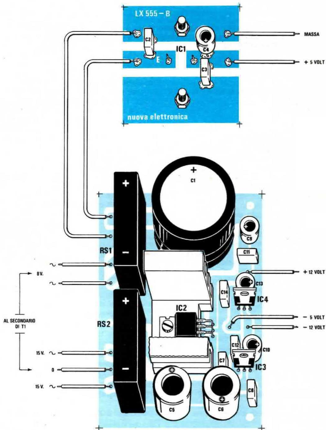
Fig. 12 Schema pratico dello stadio alimentatore. I componenti sul circuito stampato LX.555/B (vedi IC1) andranno stagnati direttamente sul lato rame.
