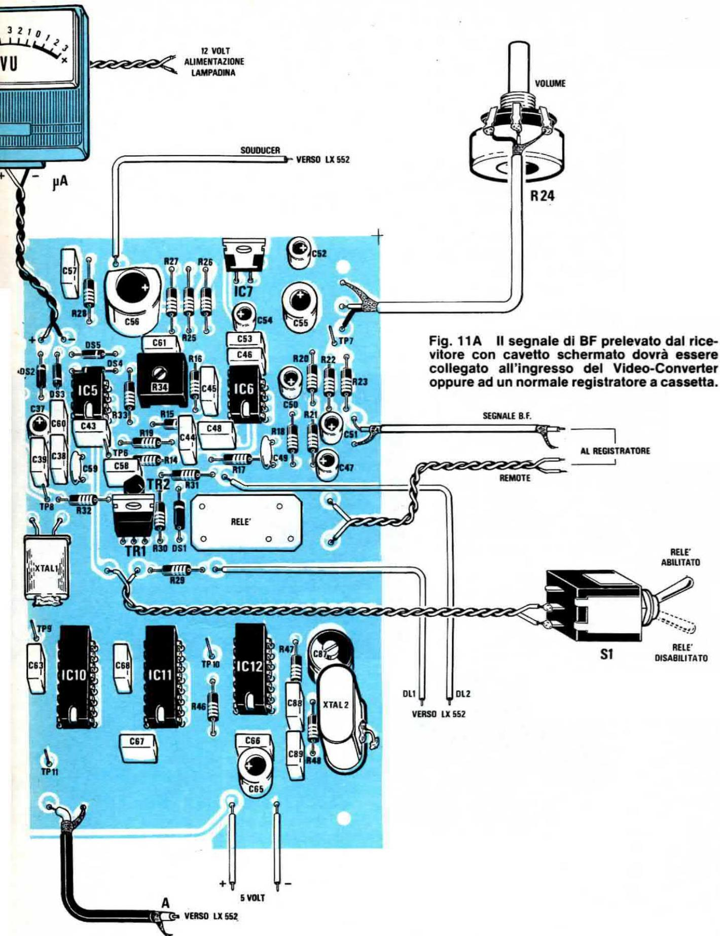
Fig. 11A Il segnale di BF prelevato dal ricevitore con cavetto schermato dovrà essere collegato all'ingresso del Video-Converter oppure ad un normale registratore a cassetta.
