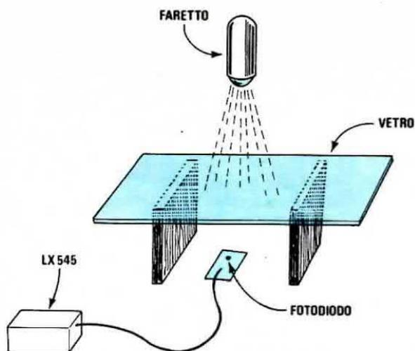
**Fig. 8** Per controllare la trasparenza di carta, un foglio di lastre di plastica o altro, bisognerà tenere il fotodiodo e la lampada sempre ad una distanza fissa.
