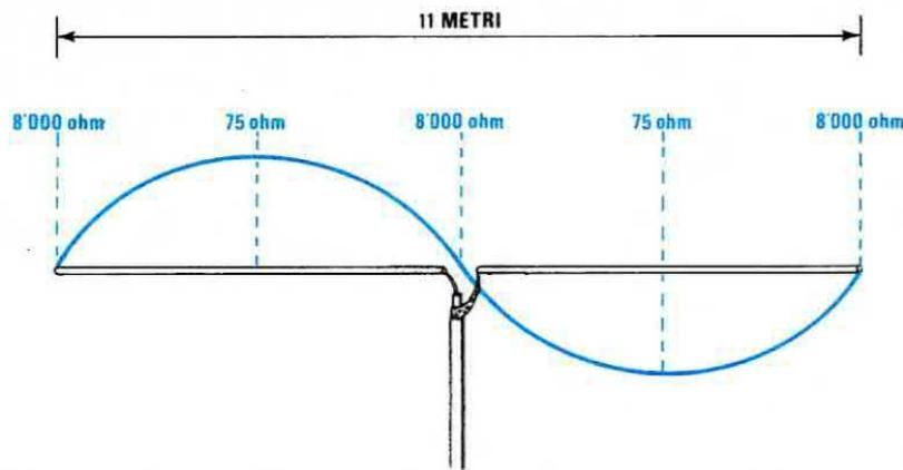
**Fig. 22** Sul n. 86/87 erroneamente vi abbiamo consigliato di utilizzare un'antenna lunga un'onda intera anziché mezza onda, in questo caso avendo collegato il cavo coassiale al centro e trovandosi in questo punto 8.000 ohm (nodi di corrente) l'antenna risulta totalmente disadattata quindi le perdite risultano totali. Per risolvere questo problema vi mandiamo alla fig. 23.
