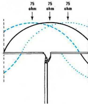
**Fig. 20** Anche se l'antenna risulta più corta del richiesto, la semionda positiva non avendo una lunghezza sufficiente per completare il suo ciclo, utilizzerà di questa la parte mancante, ed al termine di questa ripartirà la semionda negativa. Anche in questo caso al centro dell'antenna non ci ritroveremo mai con un VENTRE di corrente.
