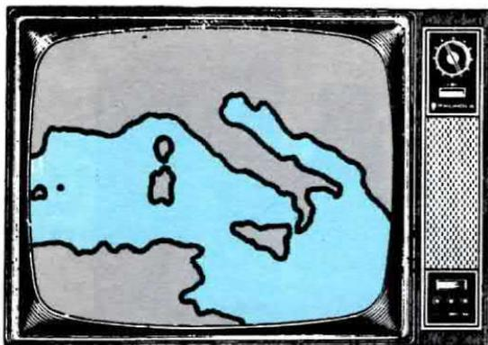
**Fig. 17** Quando capterete l'immagine CO3 (vedi fig. 10) che riguarda l'Italia constaterete che tutta la nostra penisola riempirà lo schermo del televisore (vedi anche fig. 1). Questa immagine come già spiegato la potremo ingrandire X2 e X4 e con il massimo ingrandimento otterremo anche la massima definizione.
