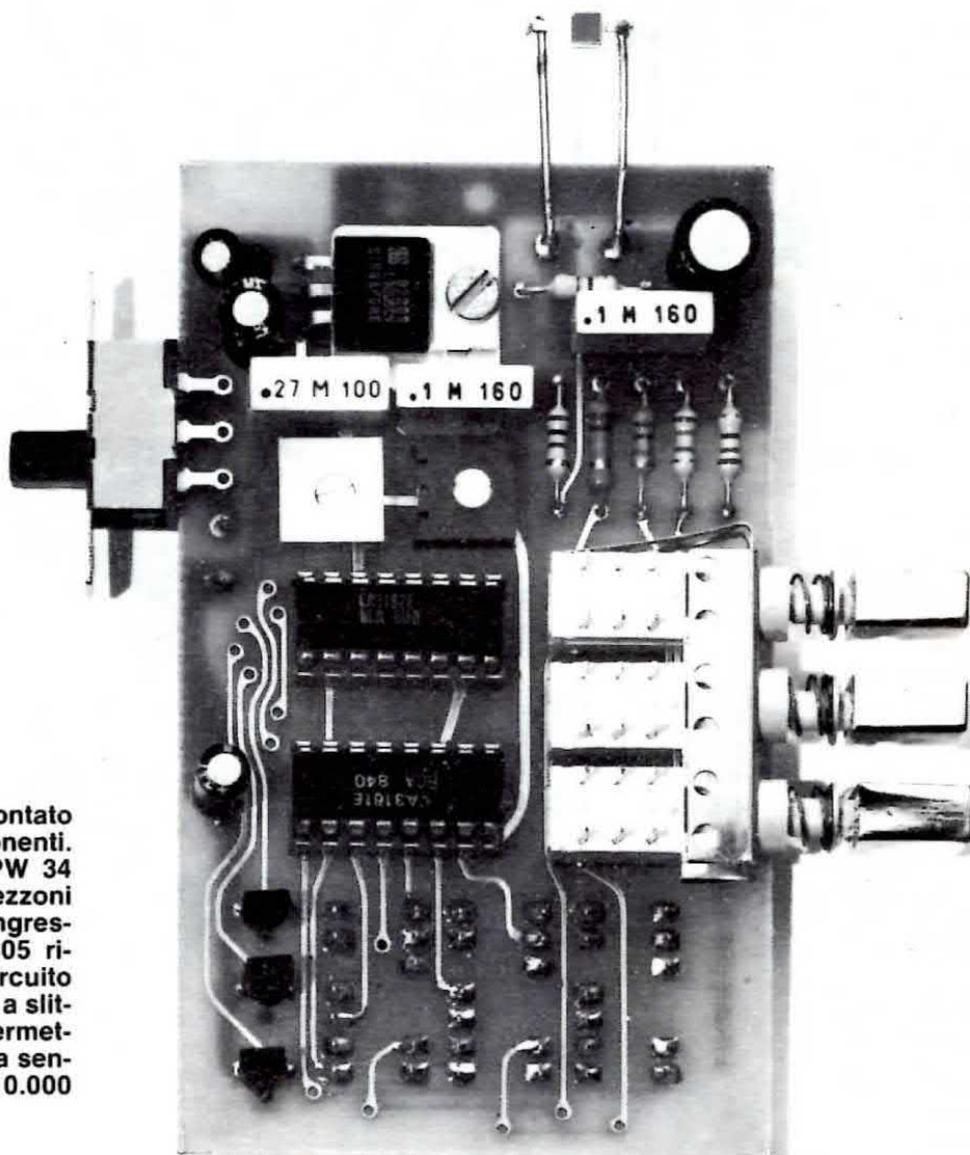
Foto del Luxmetro montato visto dal lato dei componenti. Si noti il fotodiode BPW 34 collegato con due spezzoni di filo sui terminali d'ingresso e l'integrato uA 7805 ripiegato e fissato sul circuito stampato. I tre pulsanti a slitta posti sulla destra permetteranno di modificare la sensibilità da 100-1.000-10.000 lux fondo scala.
