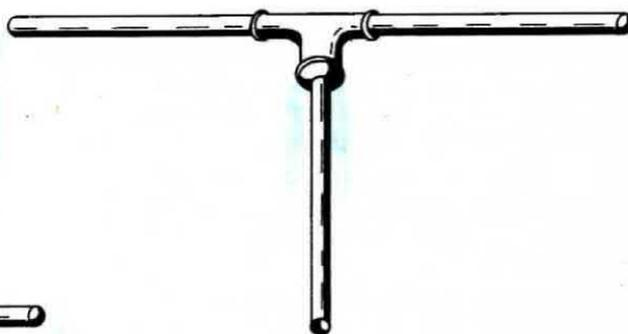
**Fig. 14** Ugualmente, se il diametro del tubo antenna risultasse minore rispetto a quello del cavo coassiale, non essendo perfetta tale giunzione (impedenza) molta acqua verrebbe dispersa. Per poter ottenere da un'antenna il massimo rendimento è necessario che la sua impedenza risulti sempre identica a quella del cavo coassiale.
