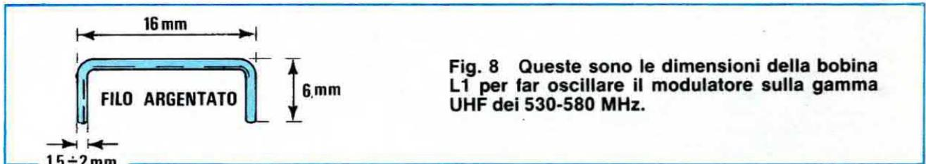
Fig. 8 Queste sono le dimensioni della bobina L1 per far oscillare il modulatore sulla gamma UHF dei 530-580 MHz.
