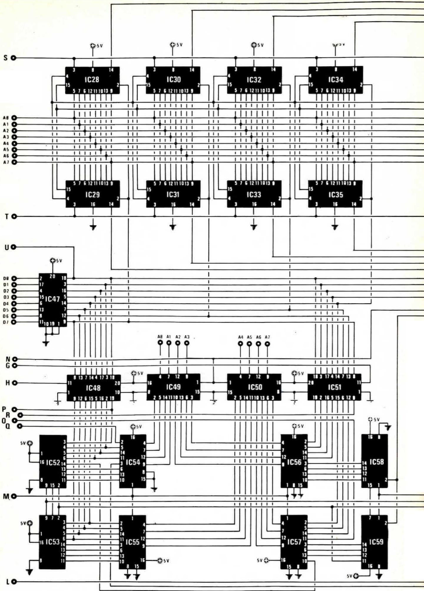
Fig. 4 Circuito elettrico dello stadio memoria e del generatore di sincronismo TV.
