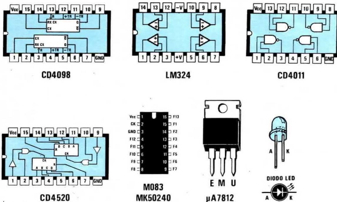
**Fig. 4** Connessioni viste da sopra degli integrati impiegati in tale realizzazione. Per i diodi led ricordatevi che il terminale da collegare al positivo di alimentazione (ANODO) è sempre più lungo del terminale da collegare a massa (KATODO).
