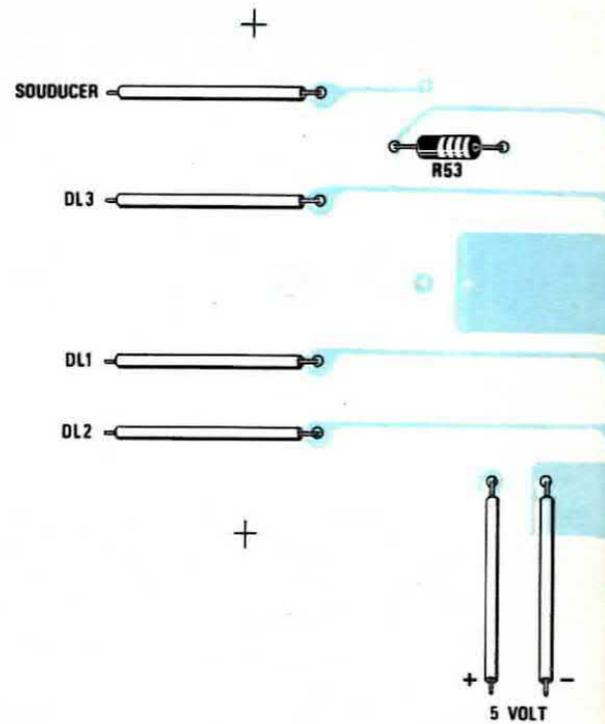
**Fig. 12** In alto, il circuito stampato siglato LX.552 visto dal lato degli integrati. I due cavi coassiali A-B da 52 ohm li collegherete al circuito stampato visibile in fig. 11 facendo attenzione a non invertirli. Anche i fili indicati con le sigle DL1-DL2-DL3-Soudecer dovranno essere collegati al circuito stampato del ricevitore nei punti indicati.
