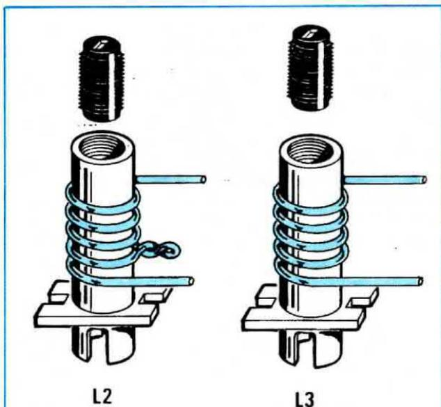
**Fig. 9** Le sole bobine L2 e L3 dovranno essere avvolte sui supporti in plastica forniti nel kit. Su L2 ad una spira verso il lato massa effettuerete una presa, necessaria per collegarla a C10 (vedi fig. 3). I supporti delle due bobine li fisserete al circuito stampato con una goccia di collante.
