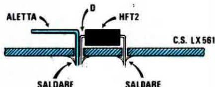
Fig. 6 L'aletta di raffreddamento dovrà essere stagnata insieme ai piedini del Drain sul lato rame del circuito stampato. Tale aletta potrà anche essere collocata rivolta sopra all'Hexfet.
