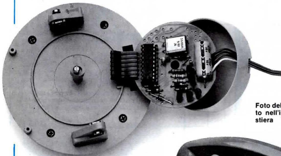
Foto del circuito montato nell'interno della tastiera
