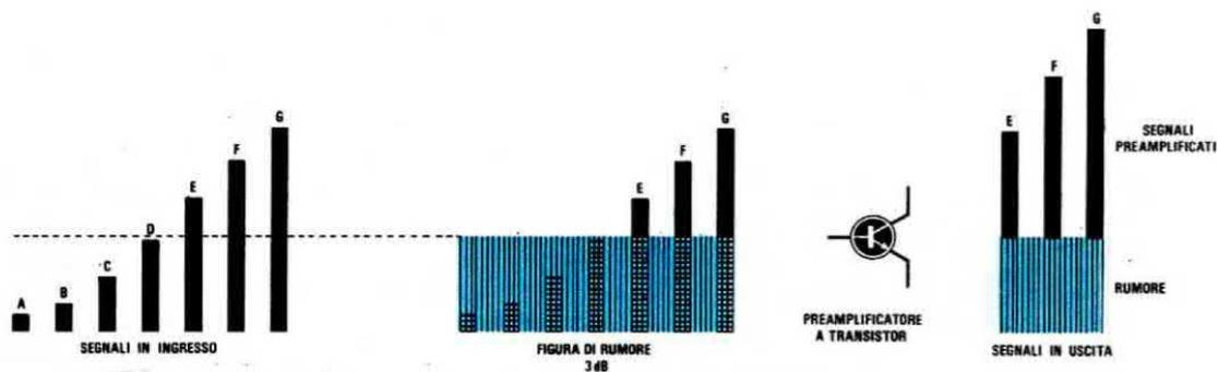
**Fig. 4** Se il primo stadio preamplificatore ha un cifra di rumore abbastanza elevata, i segnali AF che non riescono a superare il valore di tale soglia non potranno essere preamplificati. Come vedesi in figura i segnali A-B-C-D verranno sommersi dal "rumore" e solo quelli relativi ai segnali E-F-G verranno preamplificati.
