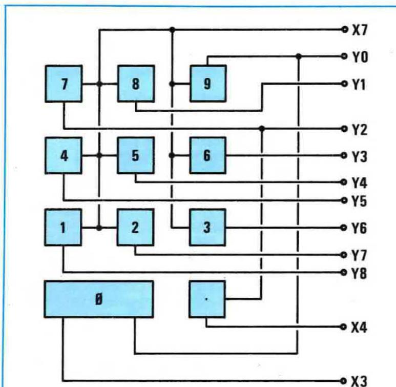
**Fig. 1** Schema elettrico della tastiera numerica che potrete abbinare a quella alfanumerica già in vostro possesso e collocare nel mobile appositamente costruito visibile nelle due foto
