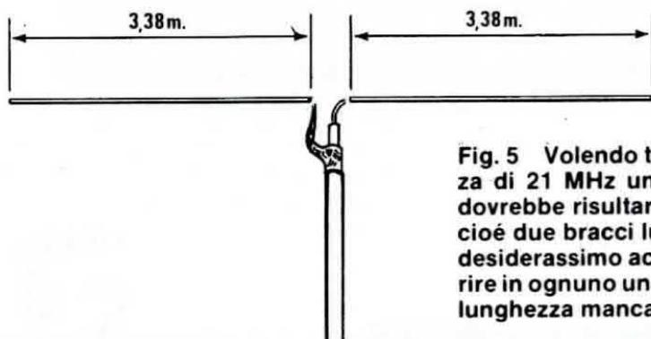
**Fig. 5** Volendo trasmettere sulla frequenza di 21 MHz un dipolo per tale gamma dovrebbe risultare lungo 6,76 metri, avere cioè due bracci lunghi 3,38 metri l'uno, se desiderassimo accorciarlo occorrerà inserire in ognuno una bobina che compensi la lunghezza mancante.
