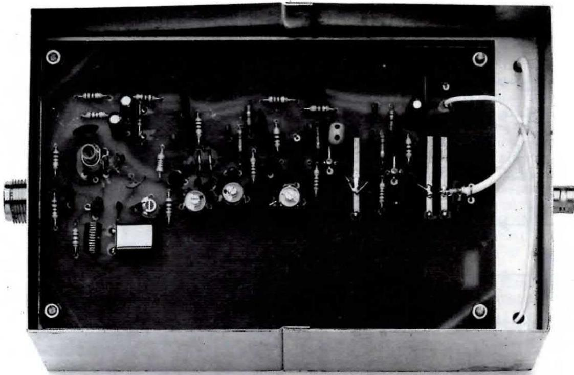
**Fig. 2** Sull'altro lato della scatola, separato da uno schermo metallico è presente lo stadio oscillatore. Si notino sulla sinistra il quarzo da 86,5 MHz, la bobina L9 (bobina verticale) e proseguendo verso destra tutti gli stadi triplicatori e duplicatori necessari per ottenere in uscita una frequenza di 1,557 GHz.
