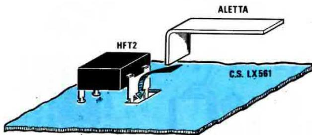
fig. 5 Una volta effettuata una stretta asola dal lato Drain dell'Hexfet HFT2 inserirete, dopo averlo ripiegato a L il sottile lamierino di ottone utilizzato come aletta dissipatrice. Questa sottile striscia di lamierino viene fornita già tagliata nel corredo del kit.
