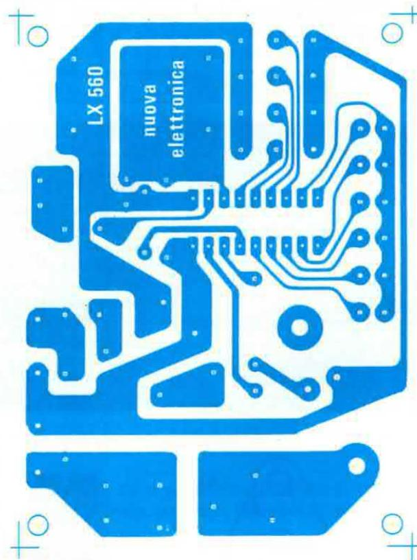
**Fig. 4** Disegno a grandezza naturale del circuito stampato richiesto per la realizzazione di questo temporizzatore.
