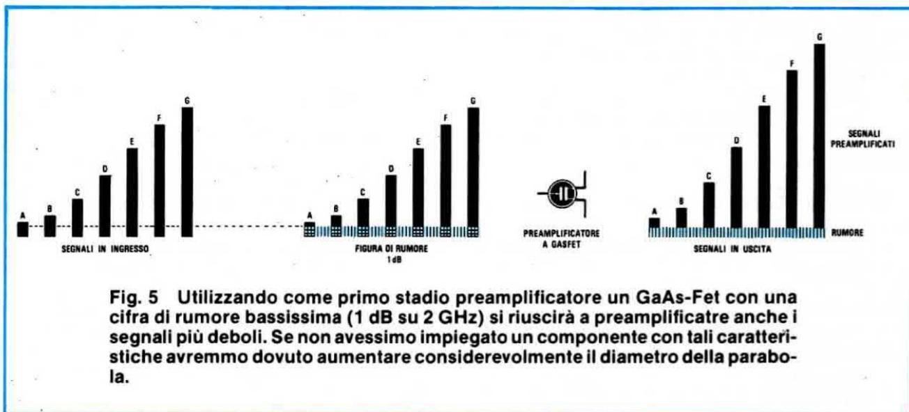
**Fig. 5** Utilizzando come primo stadio preamplificatore un GaAs-Fet con una cifra di rumore bassissima (1 dB su 2 GHz) si riuscirà a preamplificare anche i segnali più deboli. Se non avessimo impiegato un componente con tali caratteristiche avremmo dovuto aumentare considerevolmente il diametro della parabola.
