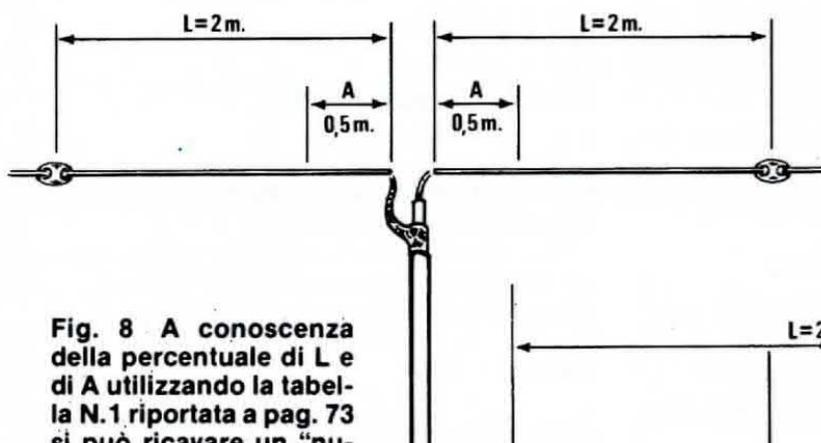
**Fig. 8** A conoscenza della percentuale di L e di A utilizzando la tabella N.1 riportata a pag. 73 si può ricavare un "numero" e con questo calcolare il valore d'induttanza in microhenry da assegnare alla bobina di compensazione. Ovviamente tale bobina dovrà essere inserita su entrambi i bracci del dipolo.
