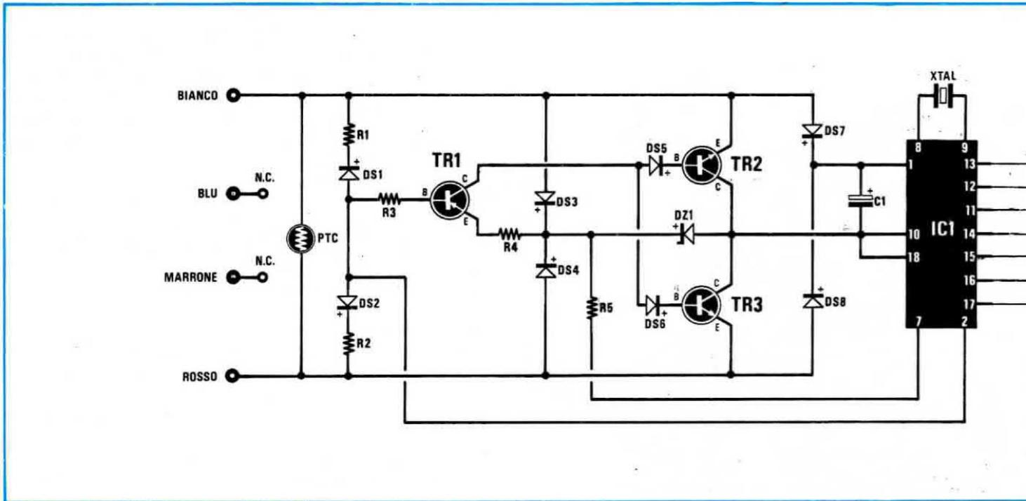
il filo bianco e viceversa, il nostro circuito funzionerà ugualmente, in quanto i tre transistor presenti nello schema hanno esclusivamente la funzione di proteggere il circuito contro questa «inversione» di polarità.
