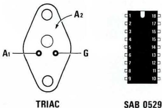
Fig. 2 Connessioni del triac viste da sotto e dell'integrato SAB.0529 viste invece da sopra.
