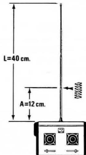
**Fig. 11** Volendo collocare la bobina di compensazione a circa 12 cm dal bocchettone, occorrerà ricalcolare il valore d'induttanza. Più collochiamo verso l'alto la bobina più aumenta il valore d'induttanza.
