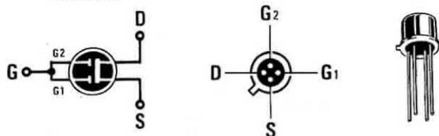
Fig. 4 Per i mosfet la disposizione dei terminali è universale. Per controllare un Mosfet con il nostro circuito è necessario cortocircuitare assieme i due terminali G1 e G2 come vedesi nel disegno riportato sulla sinistra
