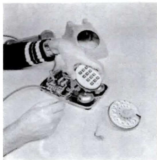
Una volta eliminato il vecchio combinatore dell'apparecchio telefonico, potrete inserire quello digitale fermandolo con le due viti.
