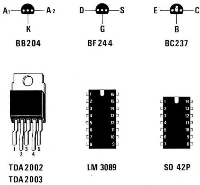
Fig.2 Connessioni viste da sotto, cioè dal lato dove i terminali fuoriescono dal corpo, del doppio diodo varicap BB.204 del fet BF.244 e del transistor BC.237. Per l'integrato LM. 3089 sostituibile con i TDA. 1200 e per l'SO.42P le connessioni sono viste da sopra. L'integrato finale di BF cioè il TDA. 2002 lo potremo sostituire senza apportare nel circuito alcuna modifica con il TDA.2003.
