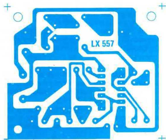
Fig. 3 Disegno a grandezza naturale del circuito stampato del quale nella foto, è possibile vederne il montaggio dal lato componenti.
