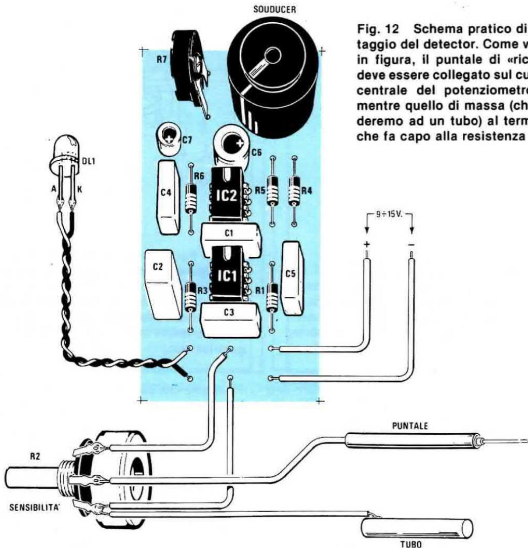
Fig. 12 Schema pratico di montaggio del detector. Come vedesi in figura, il puntale di «ricerca» deve essere collegato sul cursore centrale del potenziometro R2, mentre quello di massa (che salderemo ad un tubo) al terminale che fa capo alla resistenza R1.
