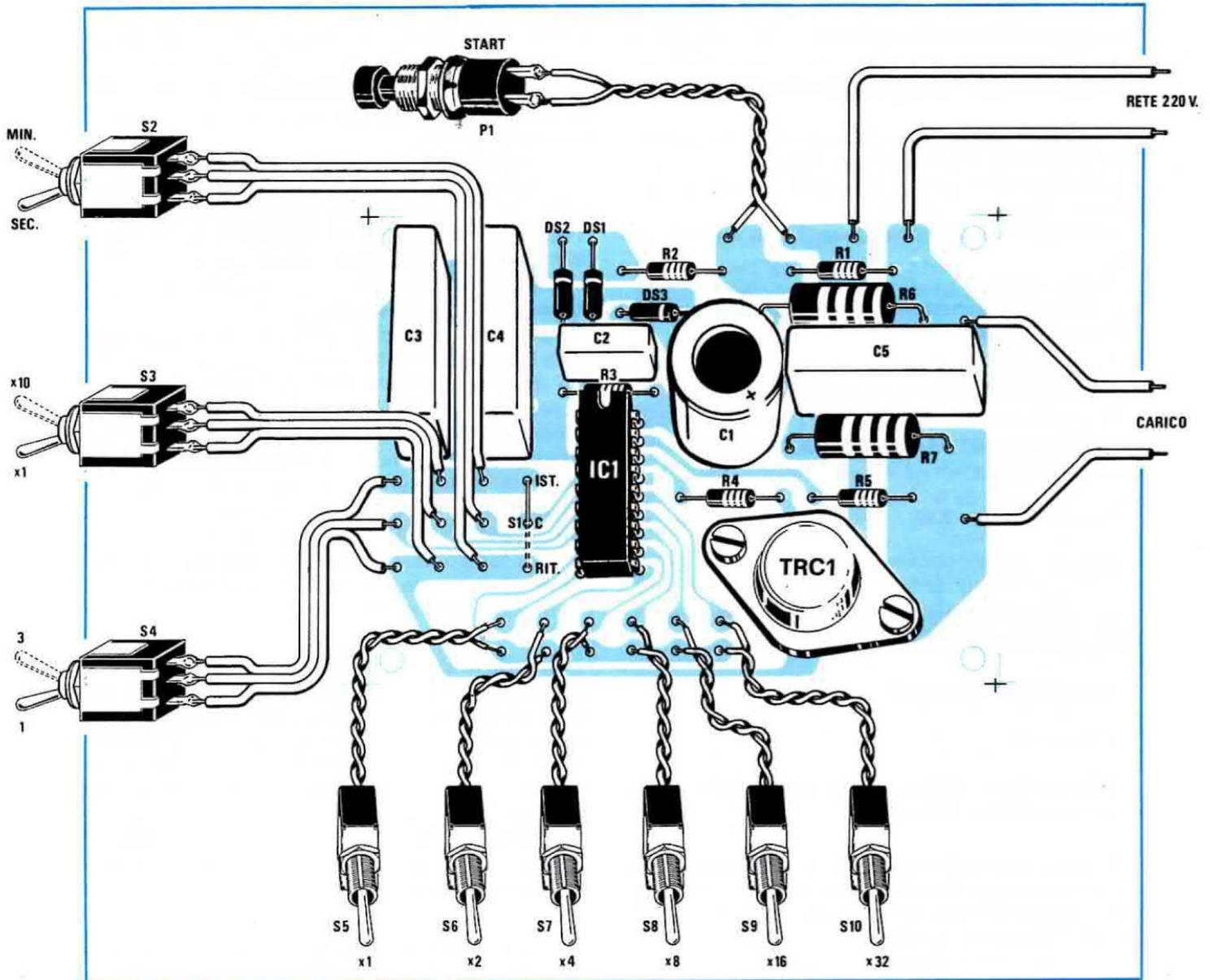
**Fig. 6** Schema pratico di montaggio del temporizzatore. Se vi interessa un temporizzatore programmato su tempi fissi, potrete sostituire tutti i deviatori con dei semplici ponticelli.
