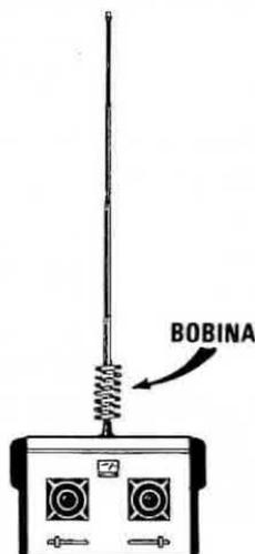
**Fig. 10** Applicando la bobina direttamente sull'innesto del bocchettone antenna, la percentuale di posizionamento bobina valore A, risulterà uguale a 0 e con i dati di L e A se ne potrà calcolare l'induttanza.
