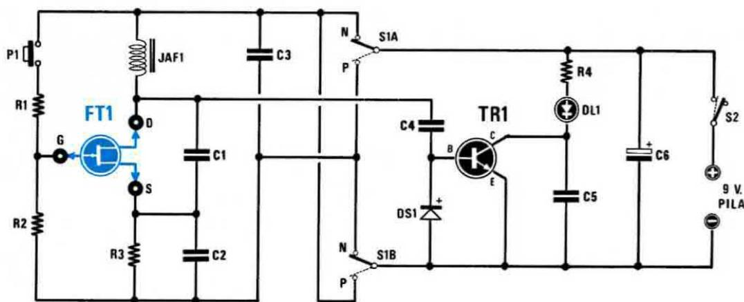
**Fig. 1** Schema elettrico
