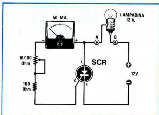
Partendo con la massima resistenza del potenziometro, lo ruoterete lentamente controllando sempre la lancetta del tester, vedrete la corrente salire lentamente fino a trovare quella posizione per la quale la lampadina si accenderà.
