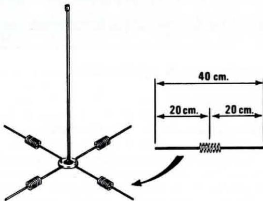
**Fig. 13** Volendo accorciare i bracci orizzontali di una Ground-Plane occorrerà come per gli altri esempi calcolare la percentuale di lunghezza utilizzata rispetto ad 1/4 d'onda e la percentuale di posizionamento della bobina su tali bracci
