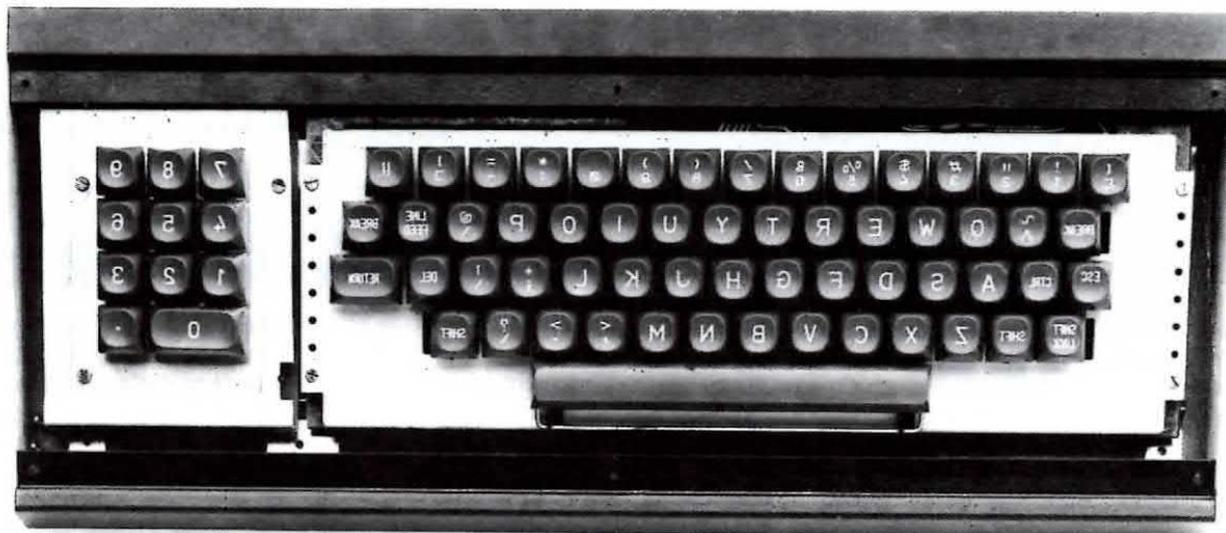
**Come per la tastiera alfanumerica (modello con tasti grigi) anche quella numerica necessita del supporto in alluminio per il sostegno degli 11 tasti. Nel fissare la tastiera numerica dovrete cercare di posizionarla correttamente in modo che tutti i tasti risultino ben centrati nel foro del pannello frontale.**
