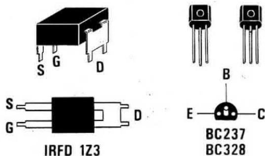
Fig. 2 Connessioni viste dei transistor e dell'Hexfet IRFD.1Z3, viste da sopra (figura in alto) e da sotto (figura in basso). Come constaterete da questo disegno, individuare i terminali G-D-S dell'Hexfet è semplice. I due terminali da un lato cortocircuitati insieme rappresentano il terminale di DRAIN, mentre dal lato opposto sono presenti il Gate e il Source.
