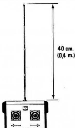
**Fig. 9** Volendo adottare in ricetrasmittitori o radiocomandati portatili antenne notevolmente accorciate, bisognerà come per i dipoli calcolare la percentuale di antenna utilizzata rispetto ad una di 1/4 d'onda.
