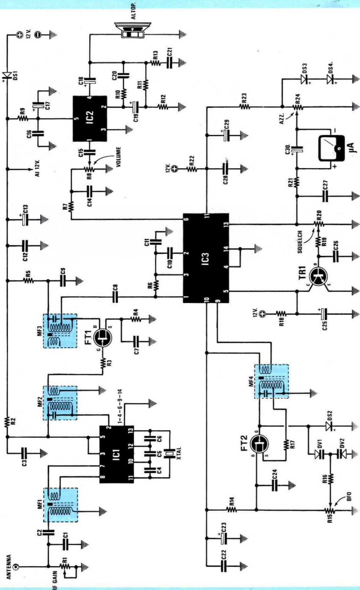
Fig. 1 Schema elettrico del ricevitore LX.562
