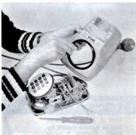
Nell'apertura circolare del coperchio inserite la guarnizione di gomma che vi verrà fornita insieme alla tastiera telefonica
