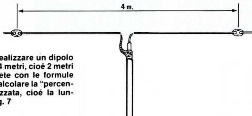
**Fig. 6** Se desiderate realizzare un dipolo la cui lunghezza risulti 4 metri, cioè 2 metri per ogni braccio, potrete con le formule riportate nell'articolo calcolare la "percentuale" di antenna utilizzata, cioè la lunghezza L riportata in fig. 7
