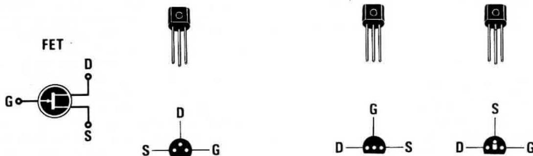
**Fig. 3** Se il fet dispone di un corpo plastico a mezzaluna e i terminali sono disposti a triangolo, quasi sempre al centro troveremo il terminale Drain, sulla sinistra il Source e sulla destra il terminale di Gate. Le connessioni sono sempre viste da sotto
