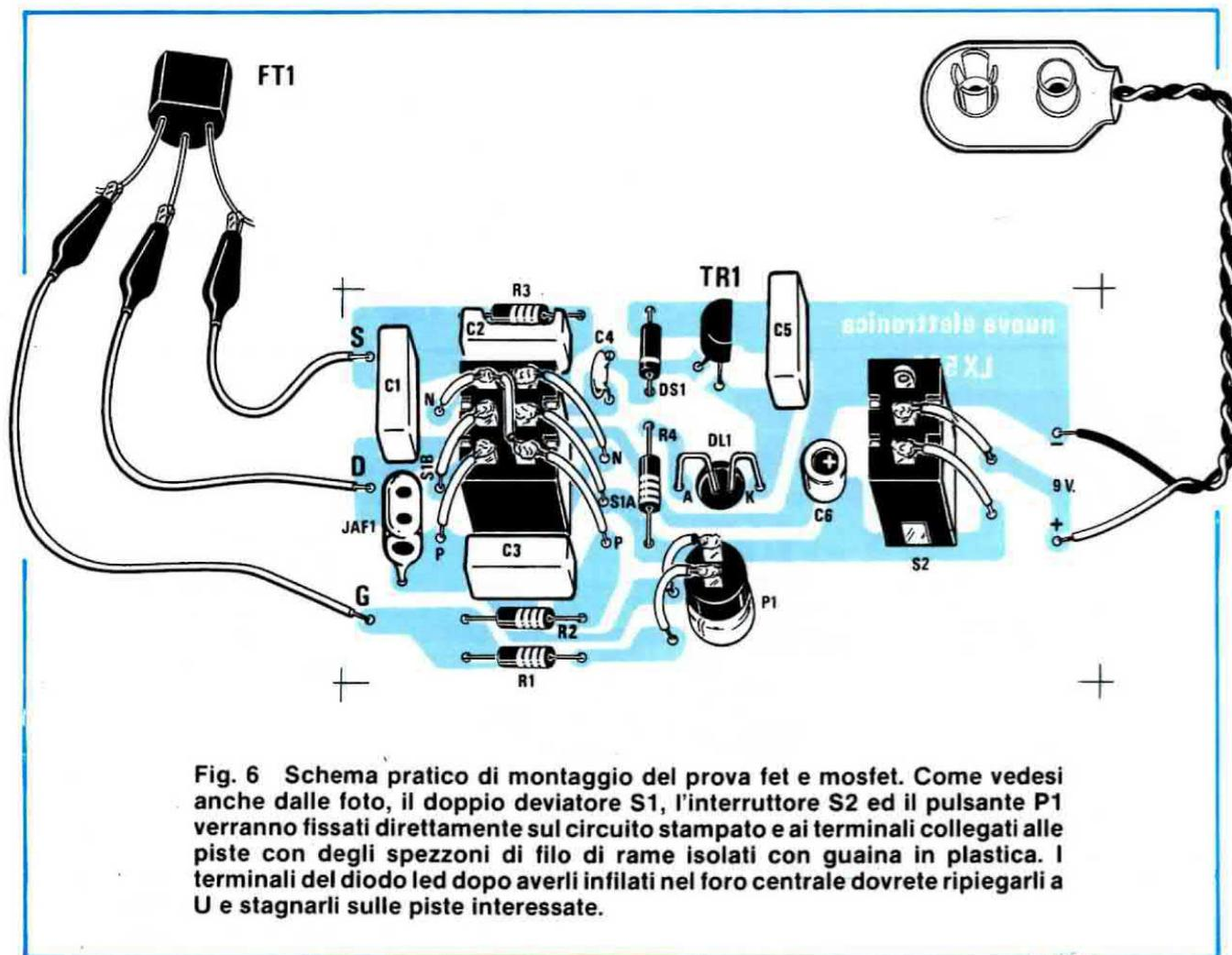
**Fig. 6** Schema pratico di montaggio del prova fet e mosfet. Come vedesi anche dalle foto, il doppio deviatore S1, l'interruttore S2 ed il pulsante P1 verranno fissati direttamente sul circuito stampato e ai terminali collegati alle piste con degli spezzi di filo di rame isolati con guaina in plastica. I terminali del diodo led dopo averli infilati nel foro centrale dovreste ripiegarli a U e stagnarli sulle piste interessate.
