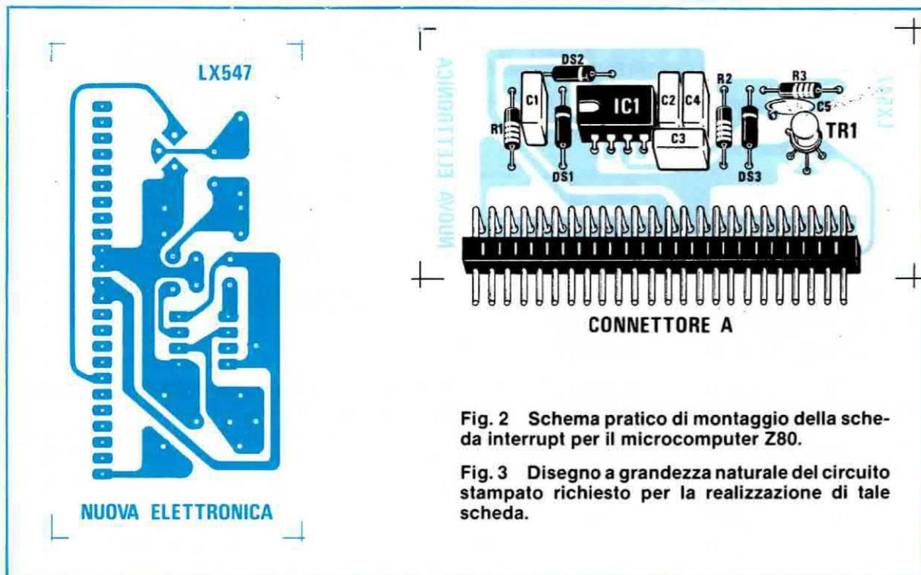
Fig. 2 Schema pratico di montaggio della scheda interrupt per il microcomputer Z80.
