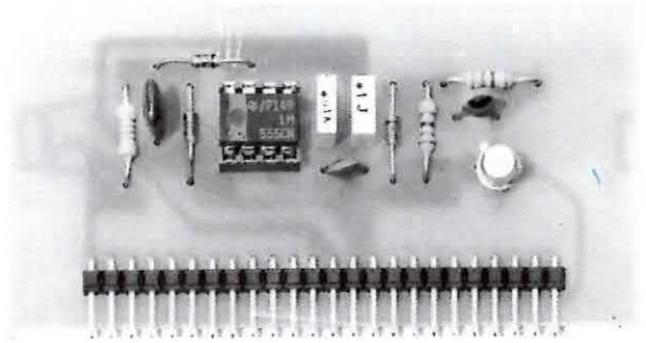
La funzione di questo circuito è principalmente quella di fornire ogni 20 millisecondi un impulso sulla pista 7A del BUS della durata di circa 1 microsecondo in modo da provocare una momentanea interruzione del programma sotto gestione e permettere alla CPU di gestire delle particolari routines che aggiungono funzioni al DOS + BASIC.
