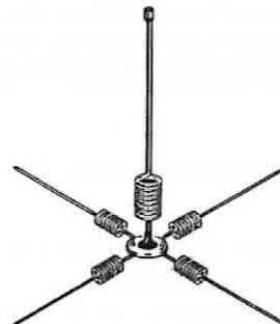
**Fig. 4** Come vedesi in questa figura è possibile anche accorciare sia lo stilo verticale che i quattro bracci orizzontali. Lo stilo verticale può essere accorciato in proporzione diversa dai bracci orizzontali.
