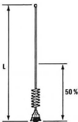
**Fig. 2** Anche per le antenne a stilo applicate sulle auto e nei ricetrasmittitori portatili la bobina di compensazione deve essere collocata partendo dal basso verso l'alto cercando di non oltrepassare il 50% della lunghezza totale.
