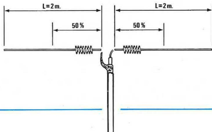
Sul numero precedente vi abbiamo insegnato come calcolare la lunghezza di un'antenna trasmittente in funzione della lunghezza d'onda, oggi apprenderete come è possibile, utilizzando una bobina di compensazione, accorciare notevolmente tale lunghezza in modo che anche con dimensioni più ridotte l'antenna riesca ugualmente ad irradiare nello spazio un segnale di alta frequenza.
