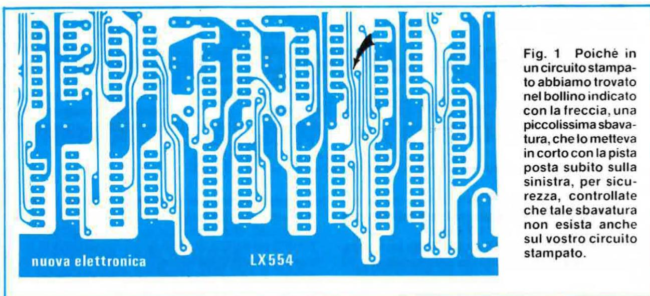
Fig. 1 Poiché in un circuito stampato abbiamo trovato nel bollino indicato con la freccia, una piccolissima sbavatura, che lo metteva in corto con la pista posta subito sulla sinistra, per sicurezza, controllate che tale sbavatura non esista anche sul vostro circuito stampato.
