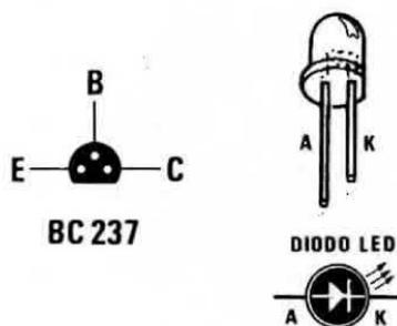
**Fig. 2** Connessioni del transistor BC.237 viste da sotto e connessioni del diodo led. Il terminale Anodo di un diodo led, cioè quello che deve essere collegato al positivo di alimentazione, risulta sempre più lungo del terminale Katodo. Invertendo i terminali il diodo led non potrà mai accendersi.
