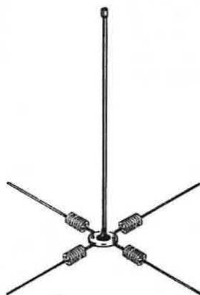
**Fig. 3** Per un'antenna Ground-Plane è possibile lasciare inalterate le dimensioni dello stilo verticale ed accorciare i soli bracci orizzontali. La bobina come vedesi in figura dovrà essere collocata su ogni braccio.
