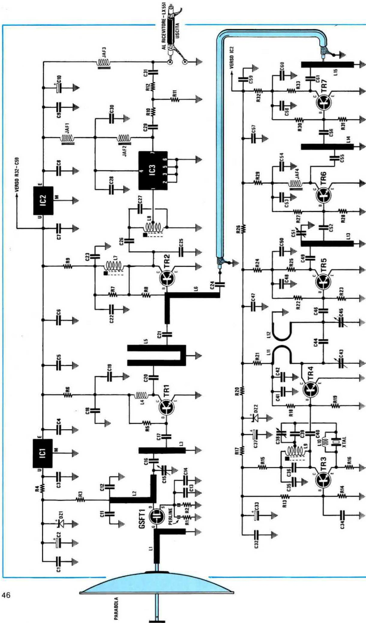
Fig. 3 Schema elettrico del preamplificatore-convertitore siglato LX.550
