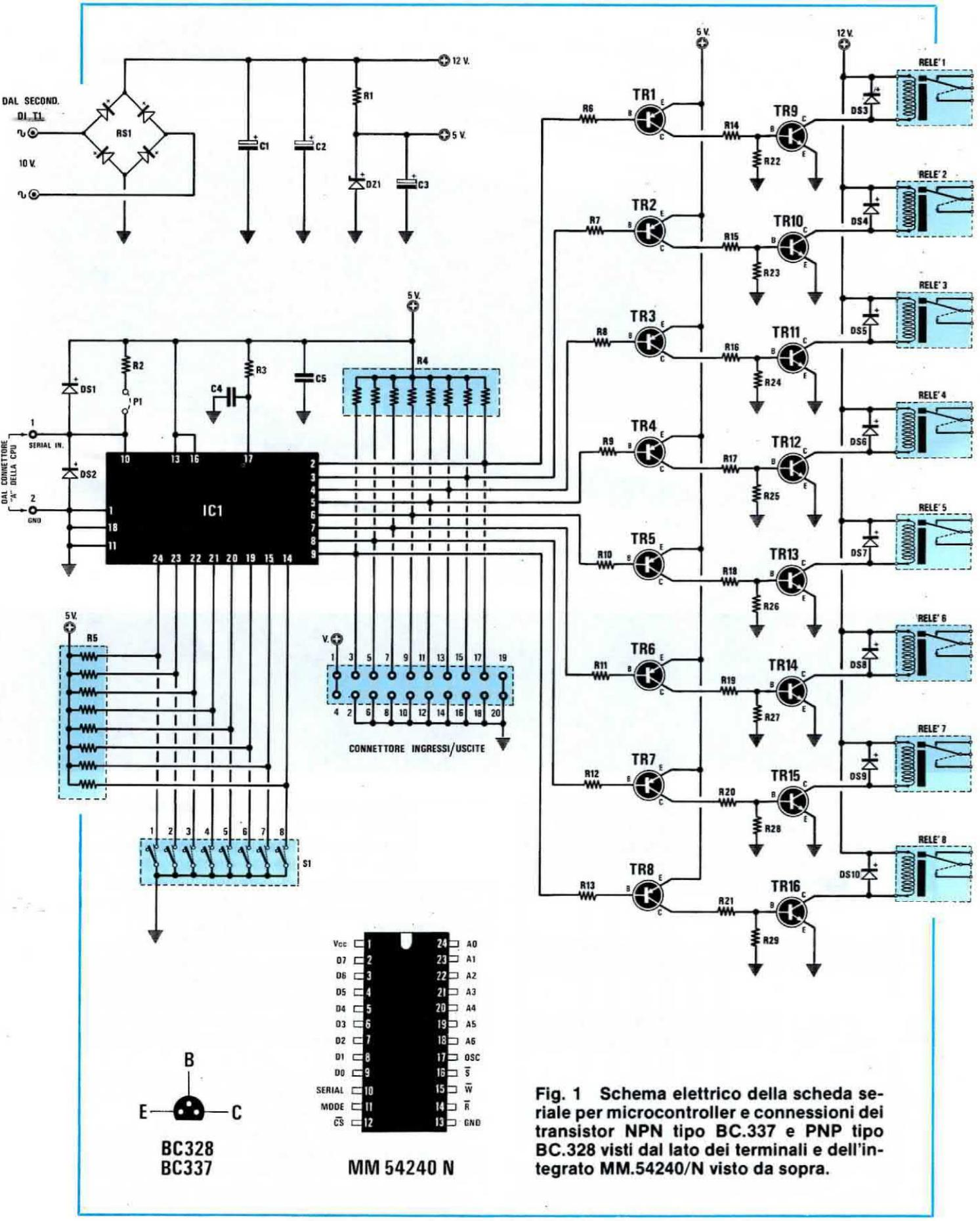
Fig. 1 Schema elettrico della scheda seriale per microcontroller e connessioni dei transistor NPN tipo BC.337 e PNP tipo BC.328 visti dal lato dei terminali e dell'integrato MM.54240/N visto da sopra.
