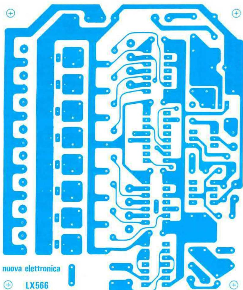
**Fig. 6** Disegno a grandezza naturale del circuito stampato. Come riportato nell'articolo questo circuito è un doppia faccia con fori metallizzati, quindi i collegamenti tra le piste inferiori e quelle superiori sono già riportati sullo stampato tramite la metallizzazione dei fori.
