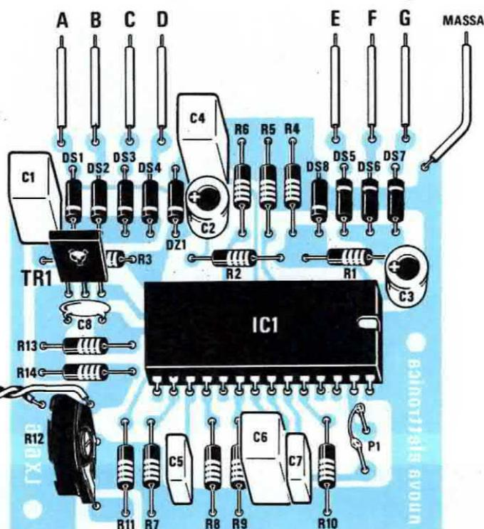
**Fig. 3** Qui sopra lo schema pratico di montaggio del promemoria per auto. Per le connessioni delle uscite A-B-C-D e E-F-G- vi consigliamo di guardare le fig. 5 e 6 della pagina successiva.
