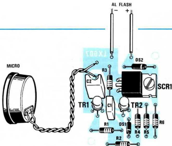
Fig. 3 Schema pratico di montaggio. Ricordiamo che il terminale centrale del diodo SCR deve essere tagliato perchè già elettricamente collegato con l'aletta.
