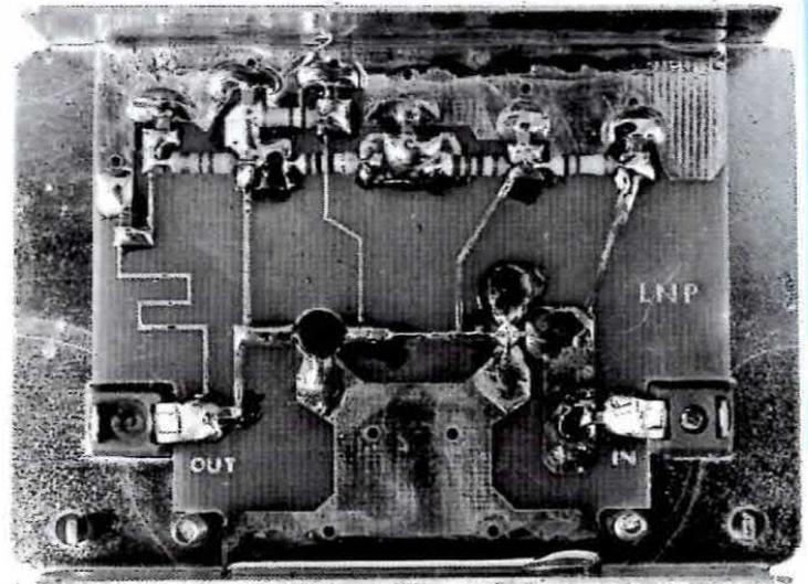
Qui sopra la foto del preamplificatore LNP-MTS2. Per ridurre la NF sui valori dichiarati, ogni circuito viene accuratamente controllato, spesso è necessario sostituire in un circuito uno dei due transistor perchè troppo "rumoroso" quindi non adatto ad amplificare segnali deboli come quelli del Meteosat.
