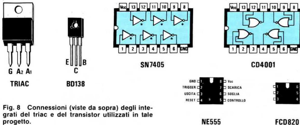
**Fig. 8** Connessioni (viste da sopra) degli integrati del triac e del transistor utilizzati in tale progetto.
