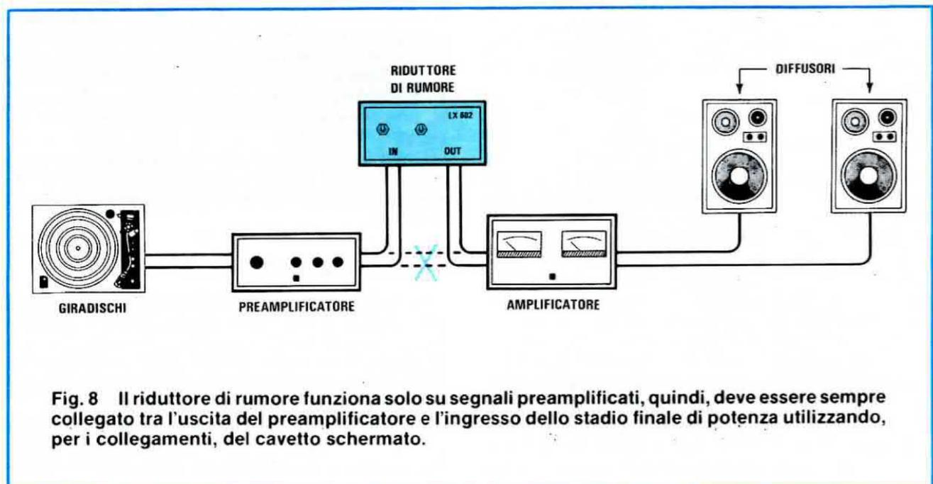
**Fig. 8** Il riduttore di rumore funziona solo su segnali preamplificati, quindi, deve essere sempre collegato tra l'uscita del preamplificatore e l'ingresso dello stadio finale di potenza utilizzando, per i collegamenti, del cavetto schermato.
