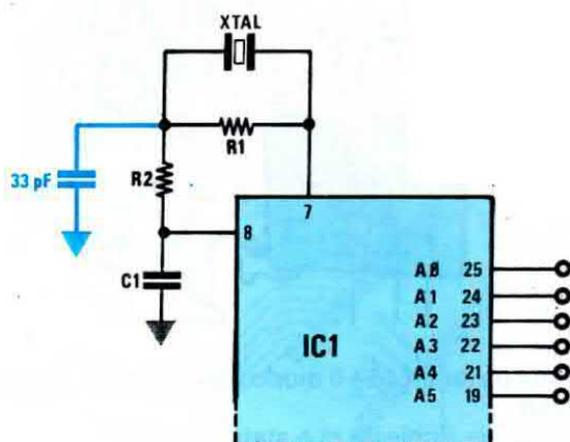
**Fig. 7** Anche se il vostro quarzo, da 4 MHz oscilla regolarmente, consigliamo SEMPRE di inserire tra la giunzione di R1-R2 e la massa un condensatore ceramico da 33 picofarad. Tale condensatore serve anche ad evitare che la scheda si blocchi in presenza di disturbi sulla rete di alimentazione.
