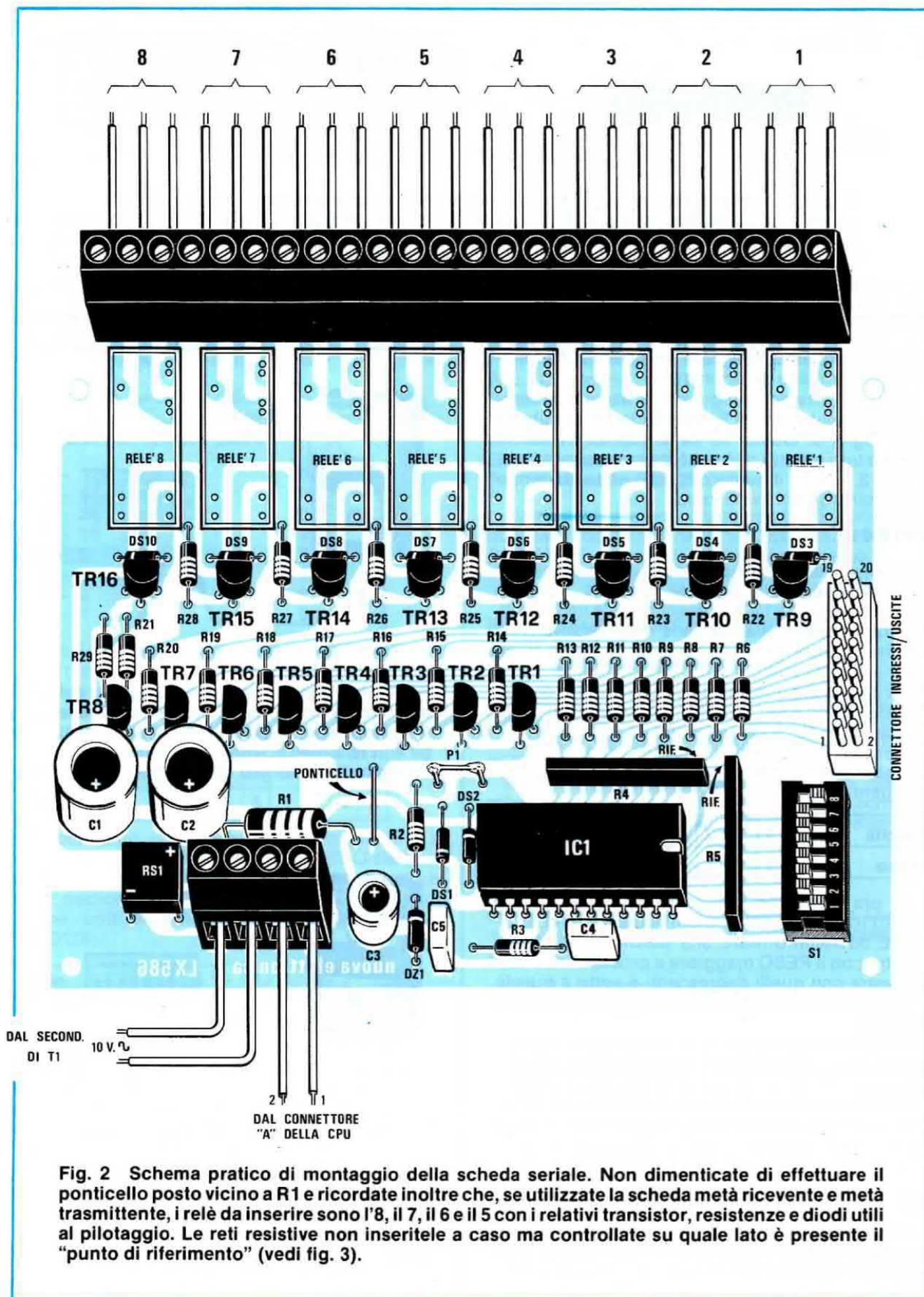
Fig. 2 Schema pratico di montaggio della scheda seriale. Non dimenticate di effettuare il ponticello posto vicino a R1 e ricordate inoltre che, se utilizzate la scheda metà ricevente e metà trasmittente, i relè da inserire sono l'8, il 7, il 6 e il 5 con i relativi transistor, resistenze e diodi utili al pilotaggio. Le reti resistive non inseritele a caso ma controllate su quale lato è presente il "punto di riferimento" (vedi fig. 3).
