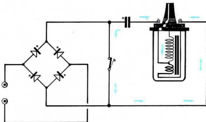
**Fig. 1** Il funzionamento di un'accensione elettronica è molto semplice. Un convertitore CC/AC converte i 12 volt in una tensione di 200-300 volt che, raddrizzata, serve per caricare un condensatore poliestere di elevata capacità, 1-2 microfarad.
