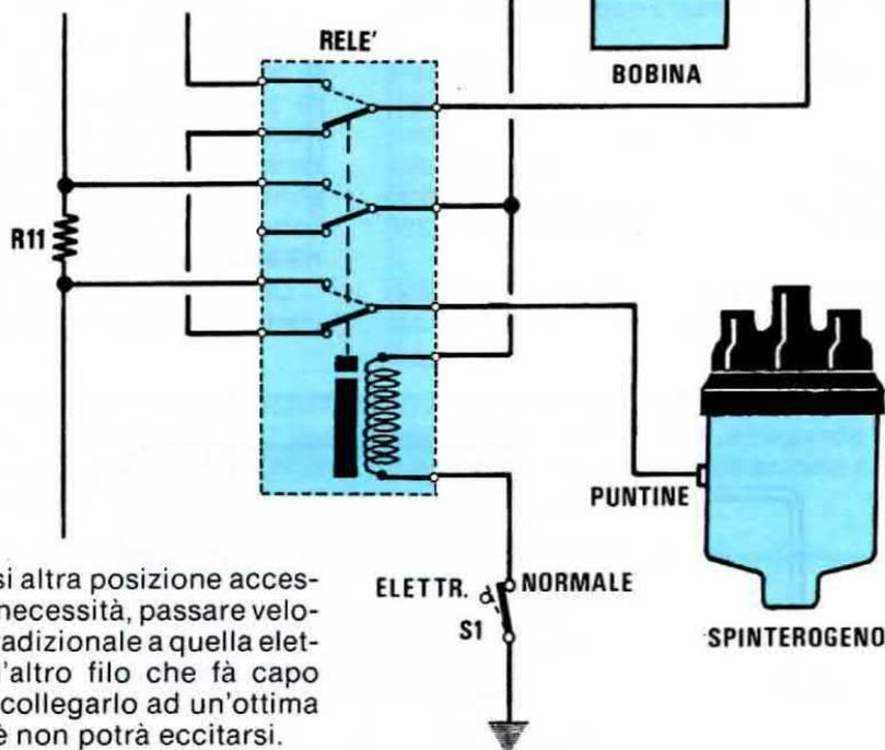
la vostra auto, o in qualsiasi altra posizione accessibile, per poter, in caso di necessità, passare velocemente dall'accensione tradizionale a quella elettronica. Ricordatevi che l'altro filo che fa capo all'interruttore S1 dovrete collegarlo ad un'ottima massa, diversamente il relè non potrà eccitarsi.
