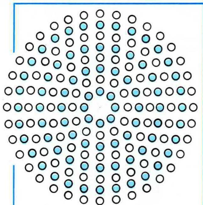
**Fig. 10** Disponendo le lampade a cerchio, e collegando alle uscite LP1-LP2 ecc. si otterrà l'effetto di un cerchio che si espande, collegandole fila per fila, alle uscite LP1-LP2 ecc. si otterranno dei raggi ruotanti.
