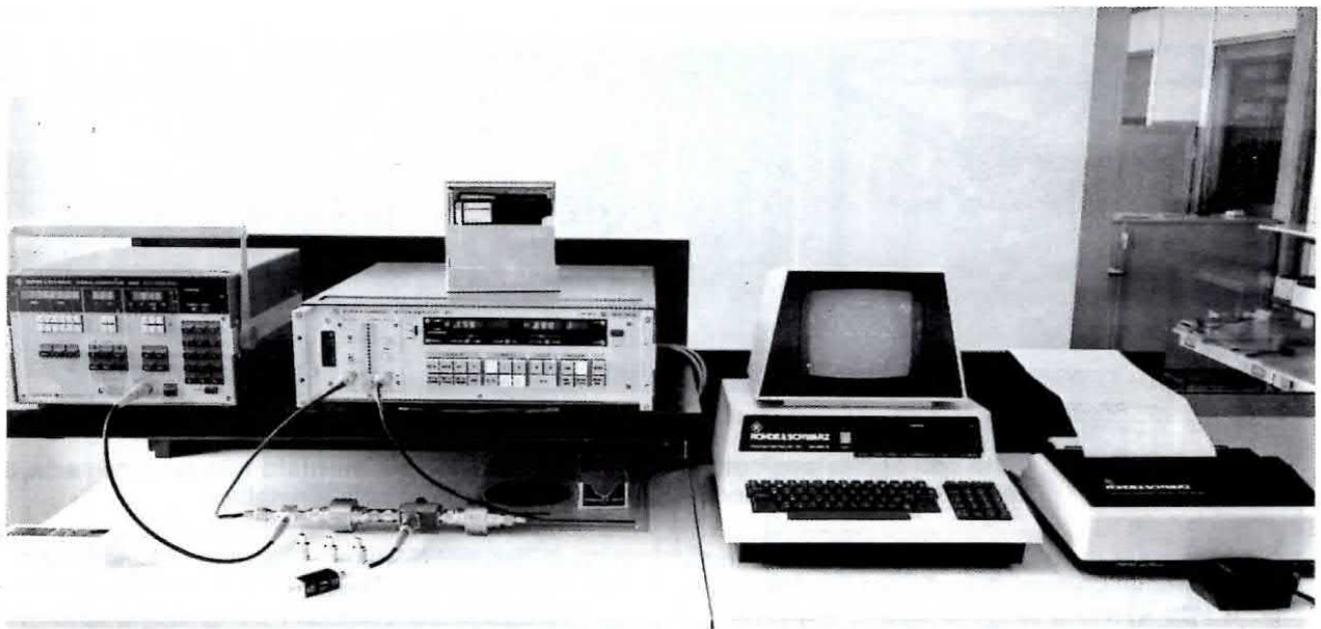
**Un computer collegato ad un analizzatore di vettore permette di visualizzare sullo schermo del monitor le curve di risposta, il guadagno di ogni stadio del preamplificatore convertitore e contemporaneamente controllare se esistono dei disadattamenti d'impedenza tra i diversi stadi**
