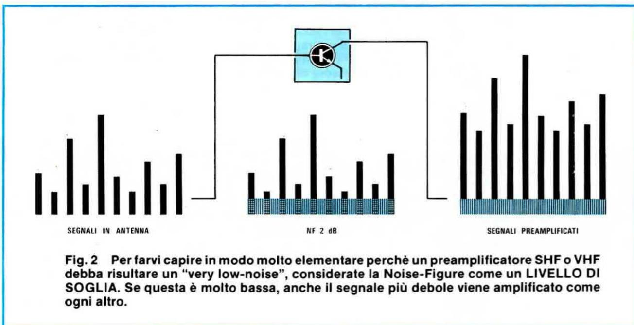
**Fig. 2** Per farvi capire in modo molto elementare perchè un preamplificatore SHF o VHF debba risultare un "very low-noise", considerate la Noise-Figure come un LIVELLO DI SOGLIA. Se questa è molto bassa, anche il segnale più debole viene amplificato come ogni altro.
