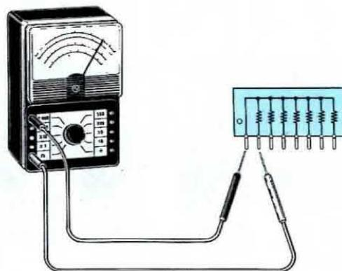
**Fig. 4** Collegando un puntale del tester sul terminale laterale che è il comune di tutte le resistenze e portando l'altro puntale, su tutti gli altri terminali si legge un identico valore ohmmico, ad esempio 10.000 ohm.
