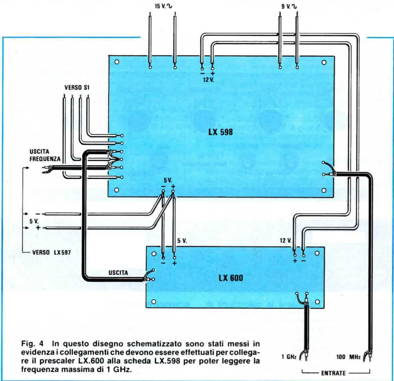
**Fig. 4** In questo disegno schematicizzato sono stati messi in evidenza i collegamenti che devono essere effettuati per collegare il prescaler LX.600 alla scheda LX.598 per poter leggere la frequenza massima di 1 GHz.
