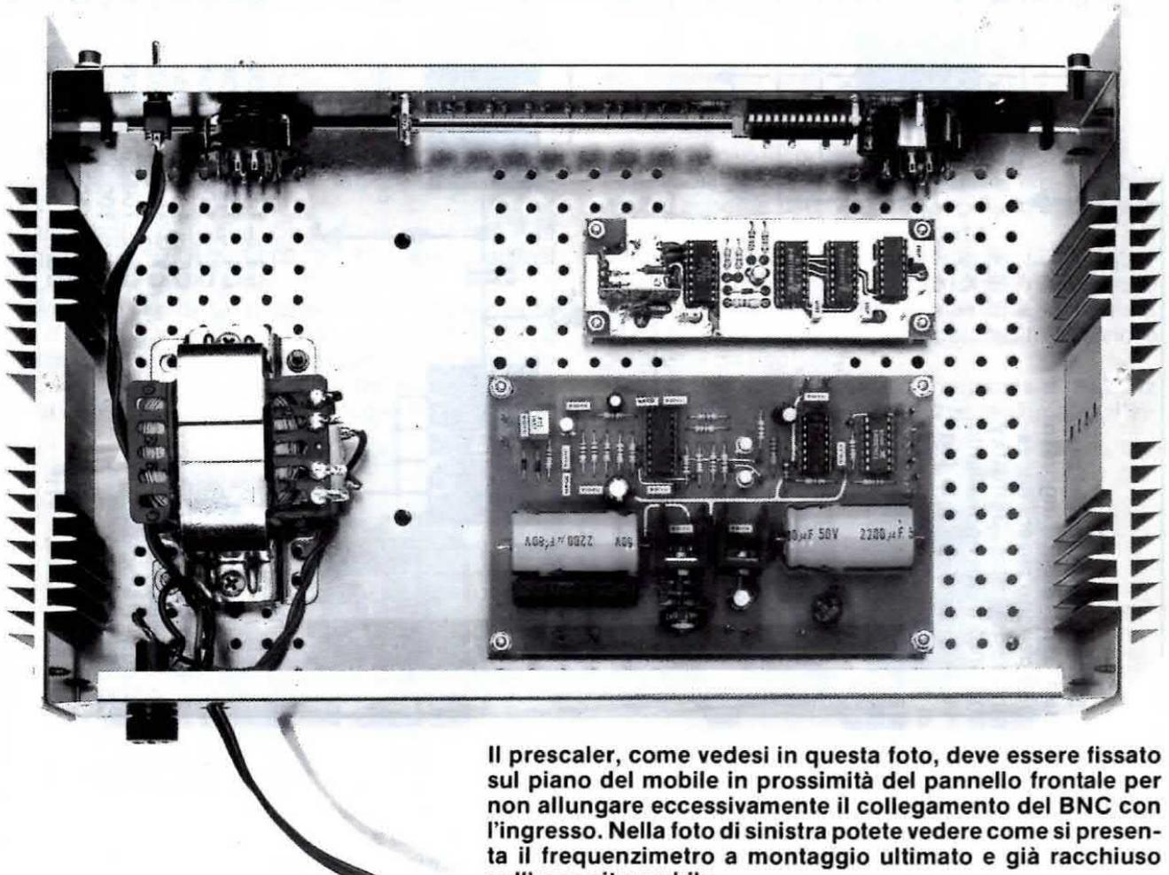
Il prescaler, come vedesi in questa foto, deve essere fissato sul piano del mobile in prossimità del pannello frontale per non allungare eccessivamente il collegamento del BNC con l'ingresso. Nella foto di sinistra potete vedere come si presenta il frequenzimetro a montaggio ultimato e già racchiuso nell'apposito mobile.
