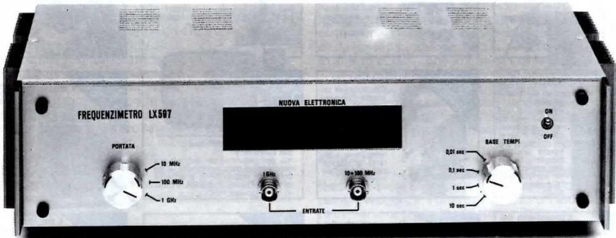
LX.597/598 pubblicato sul n. 91/92, avrete la possibilità di disporre di un validissimo frequenzimetro, che può leggere da un minimo di 1 Hz fino ad un massimo di 1 GHz, con una spesa notevolmente inferiore a quella necessaria per l'acquisto di un tale strumento in versione commerciale.
