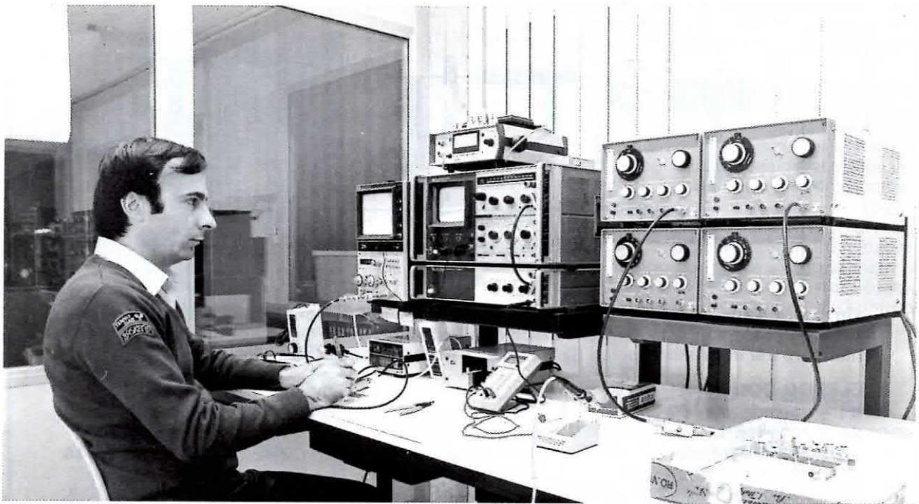
**Il preamplificatore LNP-MTS2, l'amplificatore LNA e lo stadio oscillatore-convertitore LNC, vengono montati e collaudati dalla RO.VE.R. di Sirmione sul Lago di Garda industria specializzata nel campo delle microonde. In questa foto il Sig. Romano che personalmente controlla che ogni esemplare rientri nelle caratteristiche dichiarate.**
