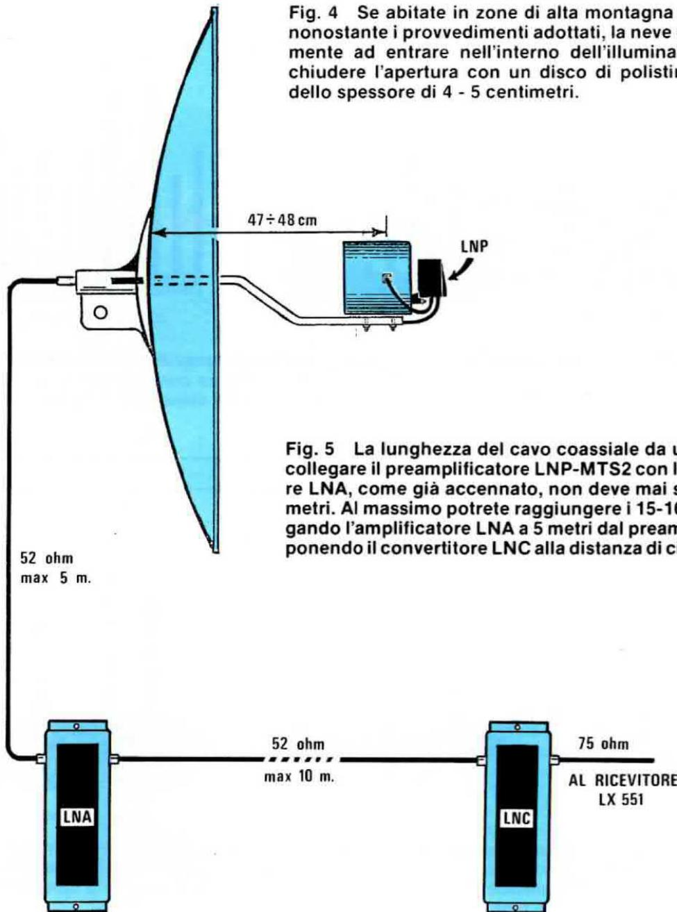
Fig. 5 La lunghezza del cavo coassiale da utilizzare per collegare il preamplificatore LNP-MTS2 con l'amplificatore LNA, come già accennato, non deve mai superare i 10 metri. Al massimo potrete raggiungere i 15-16 metri collegando l'amplificatore LNA a 5 metri dal preamplificatore e ponendo il convertitore LNC alla distanza di circa 10 metri.
