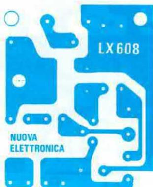
Fig. 4 Schema pratico di montaggio. Da notare a sinistra la disposizione dei terminali A-K del fotodiode. Come già accennato il terminale centrale dell'SCR deve essere tagliato.
