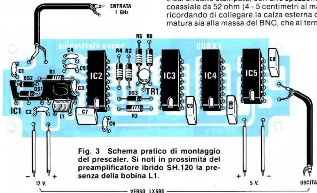
Fig. 3 Schema pratico di montaggio del prescaler. Si noti in prossimità del preamplificatore ibrido SH.120 la presenza della bobina L1.
