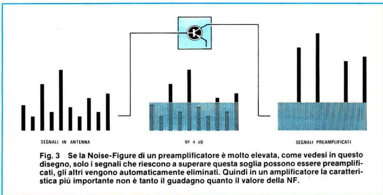
**Fig. 3** Se la Noise-Figure di un preamplificatore è molto elevata, come vedesi in questo disegno, solo i segnali che riescono a superare questa soglia possono essere preamplificati, gli altri vengono automaticamente eliminati. Quindi in un amplificatore la caratteristica più importante non è tanto il guadagno quanto il valore della NF.
