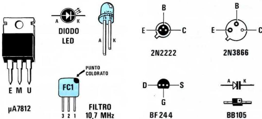
**Fig. 3** Connessioni dei transistor, dei fet, del diodo led, del diodo varicap e del filtro ceramico a 10,7 MHz utilizzati per la realizzazione del microtrasmettitore. Il filtro ceramico può essere inserito nel circuito sia in un verso che in quello opposto. Per i diodi varicap occorre invece controllare da quale lato è presente il punto di riferimento che corrisponde al katodo.
