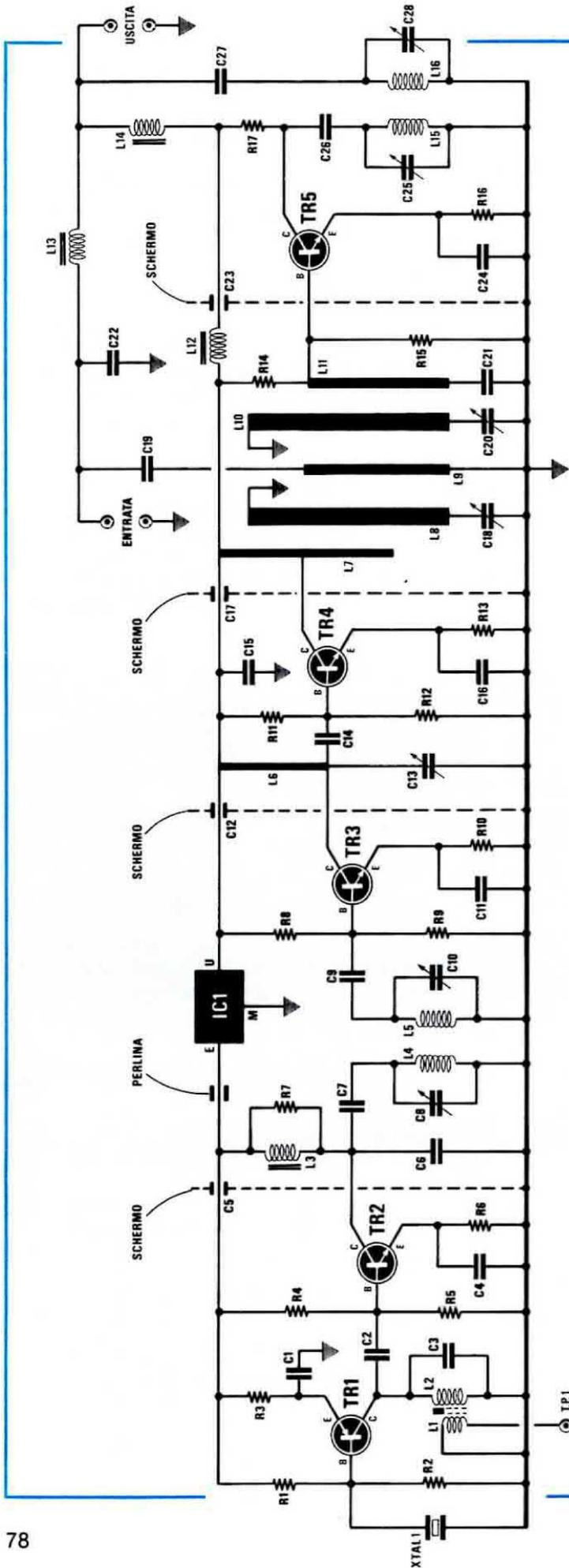
Fig. 8 Anche lo stadio oscillatore-convertitore è stato migliorato sia come caratteristiche (abbiamo eliminato tutte le subarmoniche dell'oscillatore) che come realizzazione pratica (vedi foto nella pagina di destra).
