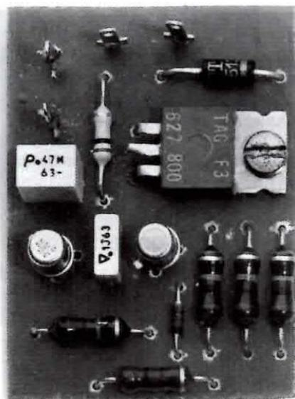
ponenti impiegati nella realizzazione del nostro semplice circuitino. Il suono o il rumore captato dal microfono piezoelettrico (in questo schema non possono essere utilizzati microfoni magnetici a causa della loro bassa impedenza) verrà applicato ad un semplice preamplificatore realizzato con i due transistor TR1 e TR2.
