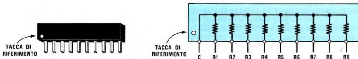
**Fig. 3** Le reti resistive impiegate in questo progetto, presentano, nel proprio interno 9 resistenze di identico valore, tutte collegate come vedesi in figura ad un solo terminale laterale che viene contraddistinto con un punto in colore stampato sul proprio corpo. Se tale punto si è cancellato potrete individuare il terminale comune come indicato nelle fig. 4 e 5.
