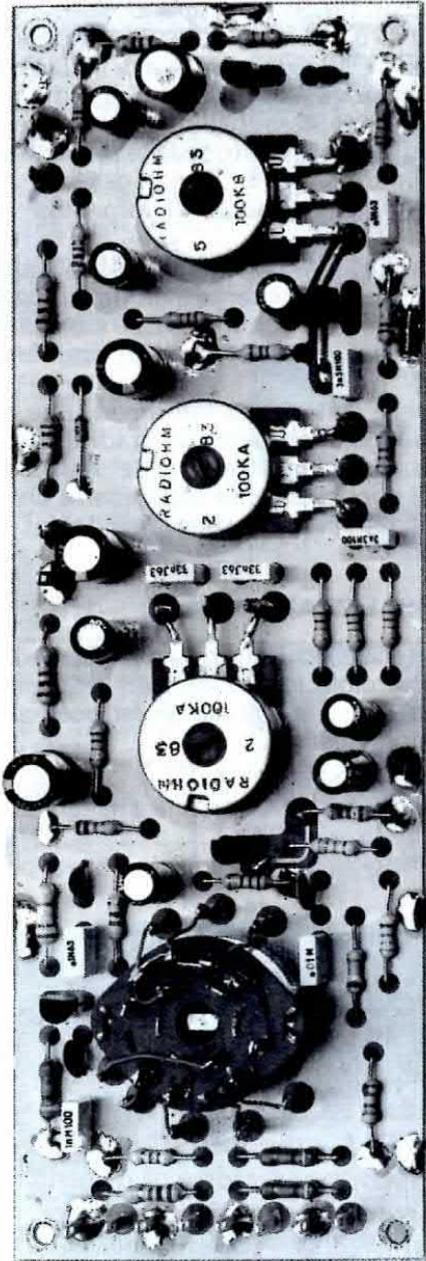
Fig. 3 Qui di lato la foto del preamplificatore montato e sotto il relativo disegno pratico. Non dimenticate di stagnare nei punti indicati le piste superiori con quelle inferiori (vicino ad R5 sotto ad R23 - R25 - R29 ecc.).
