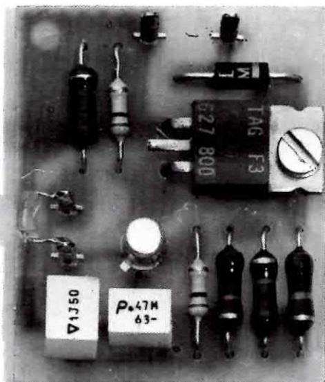
Foto del progetto. Il terminale centrale del diodo SCR deve essere lasciato scollegato in quanto risulta già collegato all'aletta metallica del corpo.
