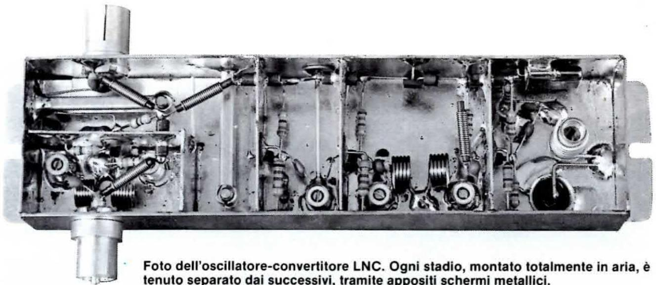
**Foto dell'oscillatore-convertitore LNC. Ogni stadio, montato totalmente in aria, è tenuto separato dai successivi, tramite appositi schermi metallici.**
