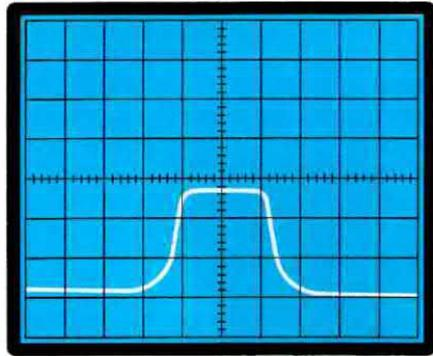
**Fig. 16** Con questo Sweep è possibile anche controllare il guadagno di uno stadio MF facendo i quadretti in verticale o facendo un confronto con la curva campione.
