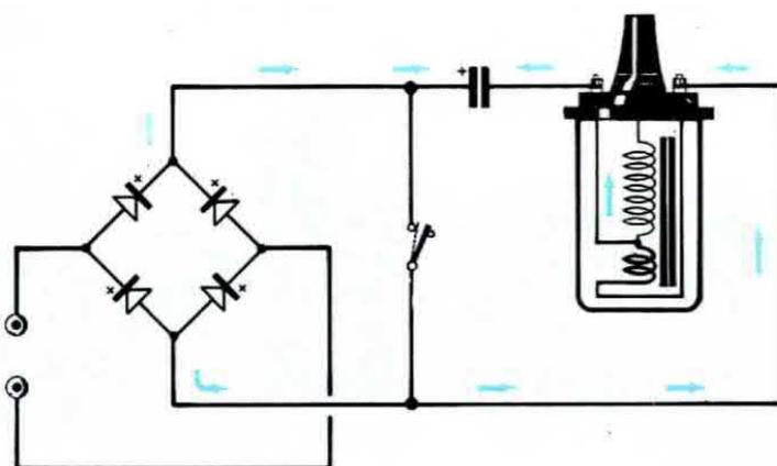
sempre ad una frequenza fissa, il nostro alimentatore switching STABILIZZATO presenta una caratteristica eccezionale: la sua frequenza di lavoro infatti è subordinata alla "velocità" della vettura.
