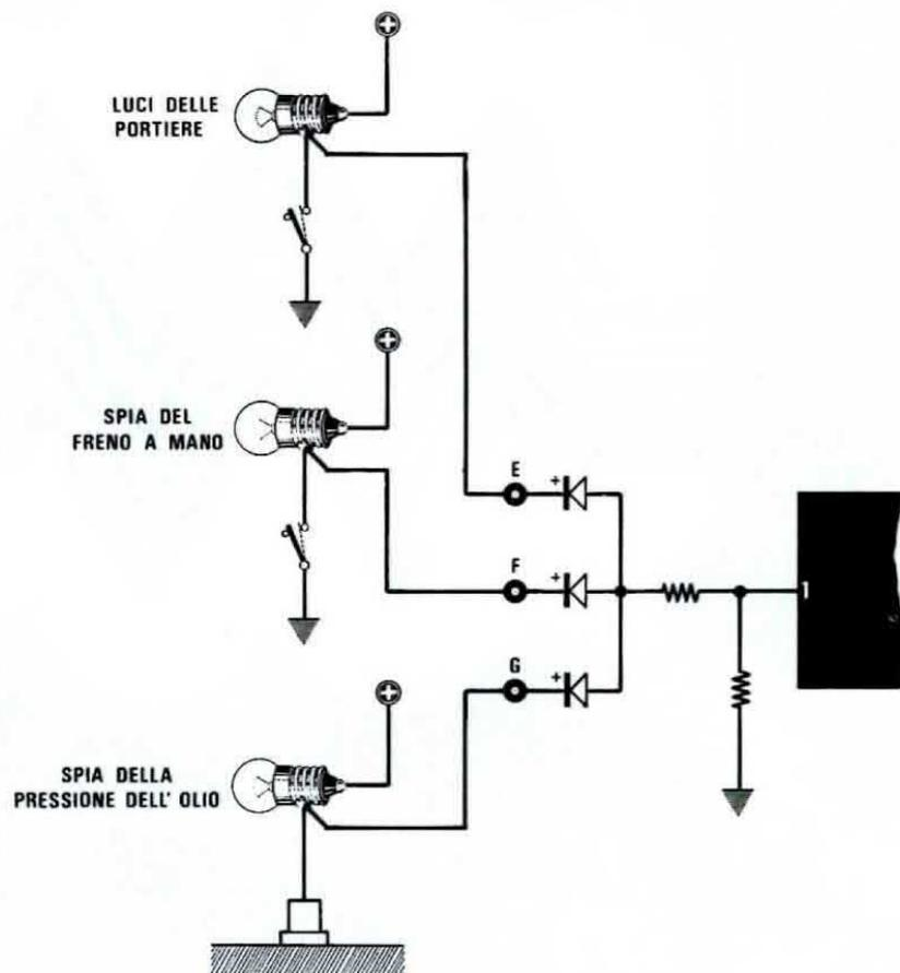
Fig. 6 I terminali E-F-G devono invece essere collegati alle lampade "spia" che accendendosi a motore in moto servono ad indicare un pericolo, ad esempio la portiera aperta, il freno a mano inserito, o la mancanza di olio. Questi ingressi a differenza di quelli di fig. 5 mettono in azione l'allarme se l'interruttore collegato alla lampada viene chiuso a massa.
