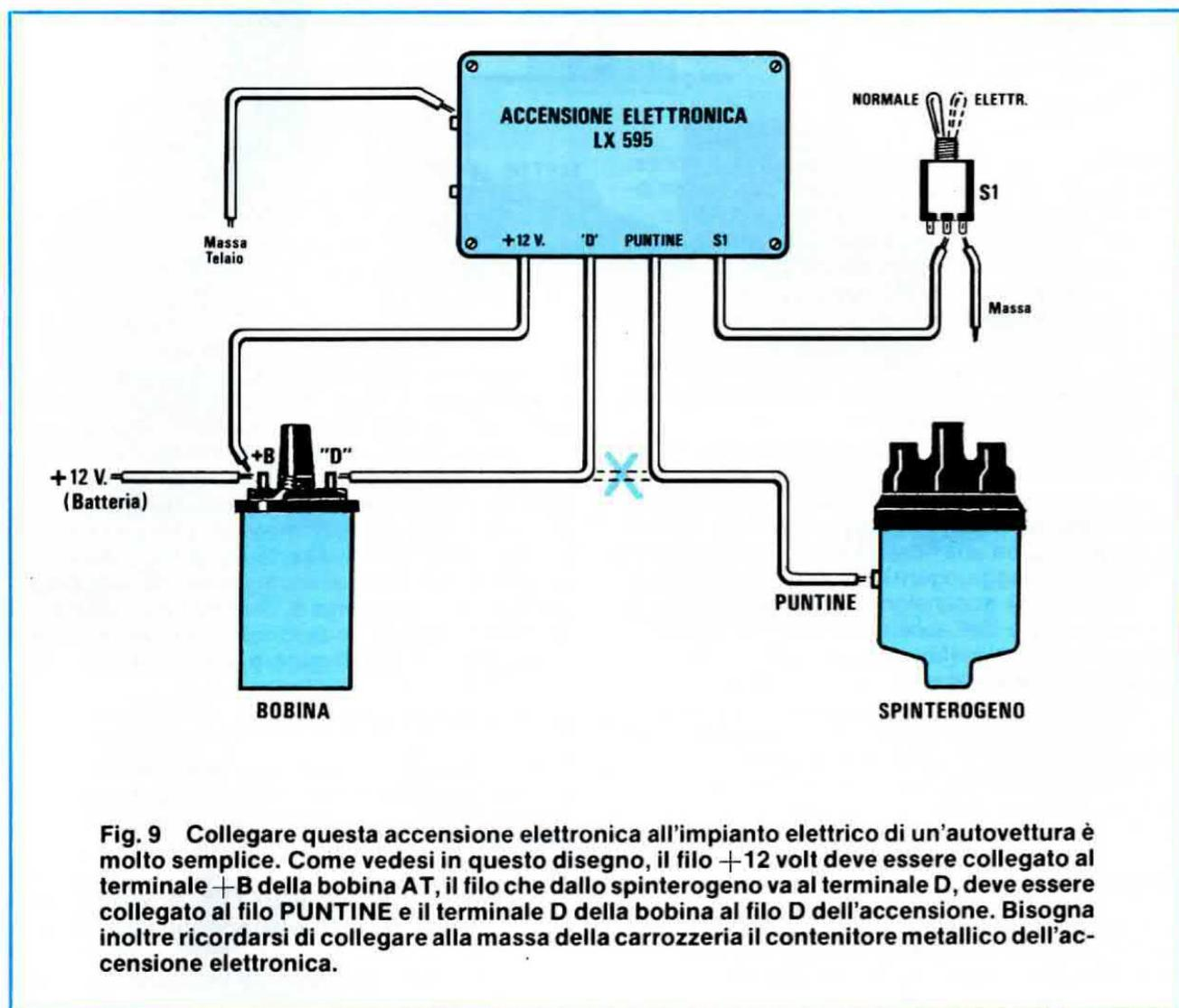
**Fig. 9** Collegare questa accensione elettronica all'impianto elettrico di un'auto-vettura è molto semplice. Come vedesi in questo disegno, il filo +12 volt deve essere collegato al terminale +B della bobina AT, il filo che dallo spinterogeno va al terminale D, deve essere collegato al filo PUNTINE e il terminale D della bobina al filo D dell'accensione. Bisogna inoltre ricordarsi di collegare alla massa della carrozzeria il contenitore metallico dell'accensione elettronica.
