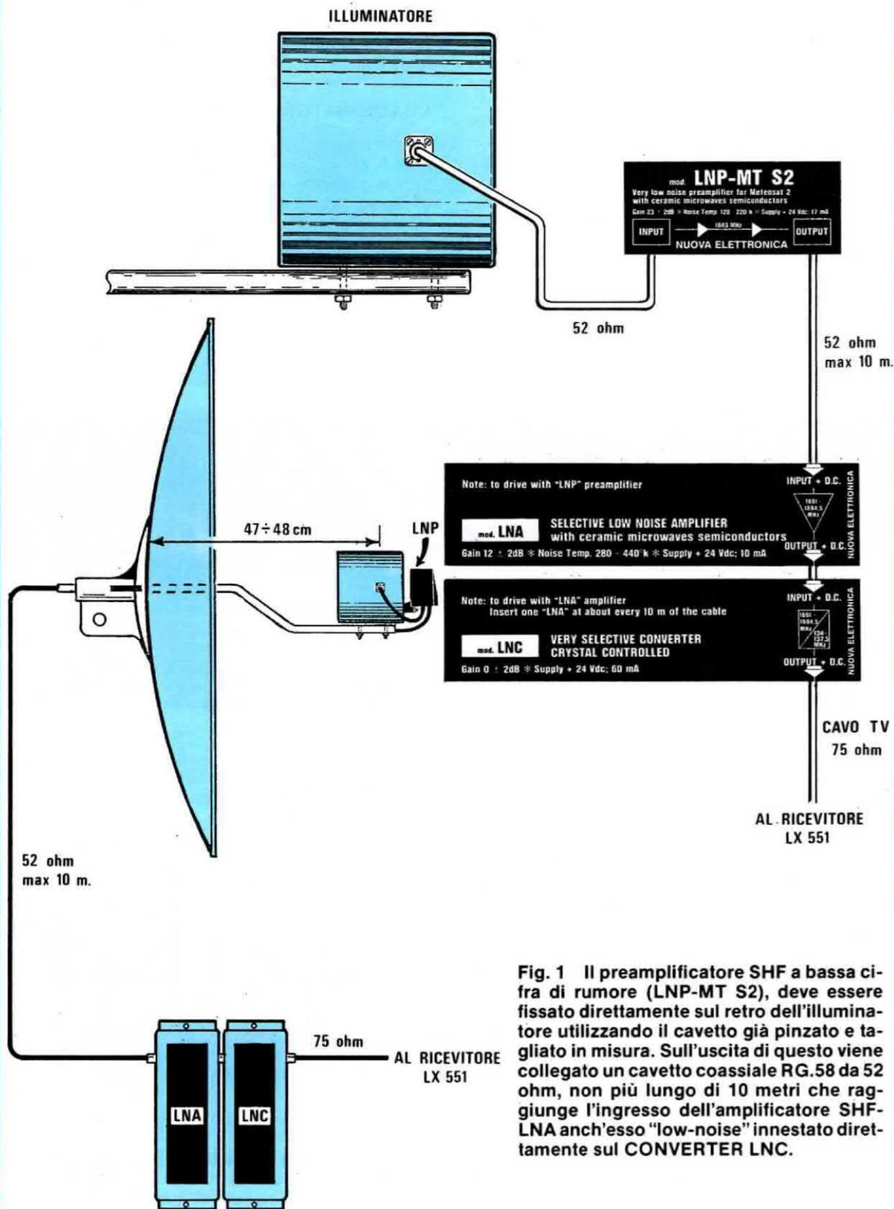
Fig. 1 Il preamplificatore SHF a bassa cifra di rumore (LNP-MT S2), deve essere fissato direttamente sul retro dell'illuminatore utilizzando il cavetto già pinzato e tagliato in misura. Sull'uscita di questo viene collegato un cavetto coassiale RG.58 da 52 ohm, non più lungo di 10 metri che raggiunge l'ingresso dell'amplificatore SHF-LNA anch'esso "low-noise" innestato direttamente sul CONVERTER LNC.
