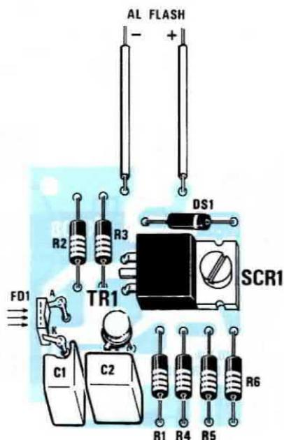
così facendo, il condensatore C1 si scarica sulla resistenza R1 da 100.000 ohm.
