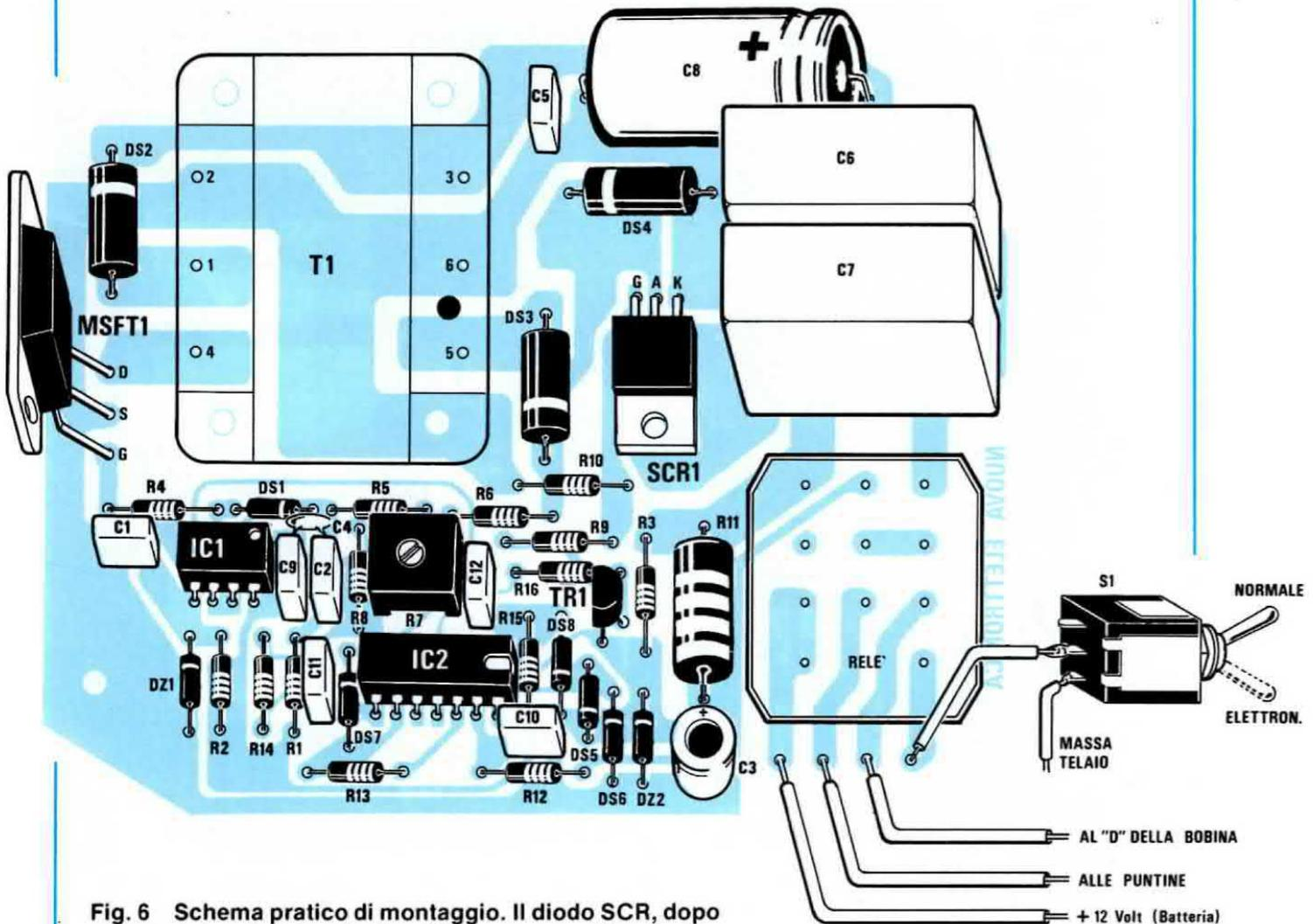
Fig. 6 Schema pratico di montaggio. Il diodo SCR, dopo averne ripiegato il terminale ad L, deve essere fissato con una vite e dado al circuito stampato applicando sotto alla sua aletta una rondella o un dado per tenerlo distanziato dalla basetta di circa 2 mm.
