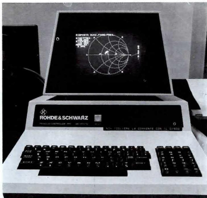
**Il computer collegato all'analizzatore di vettore è in grado di disegnare sullo schermo del monitor la carta di Smith dalla quale si può rilevare se esistono dei disadattamenti d'impedenza.**
