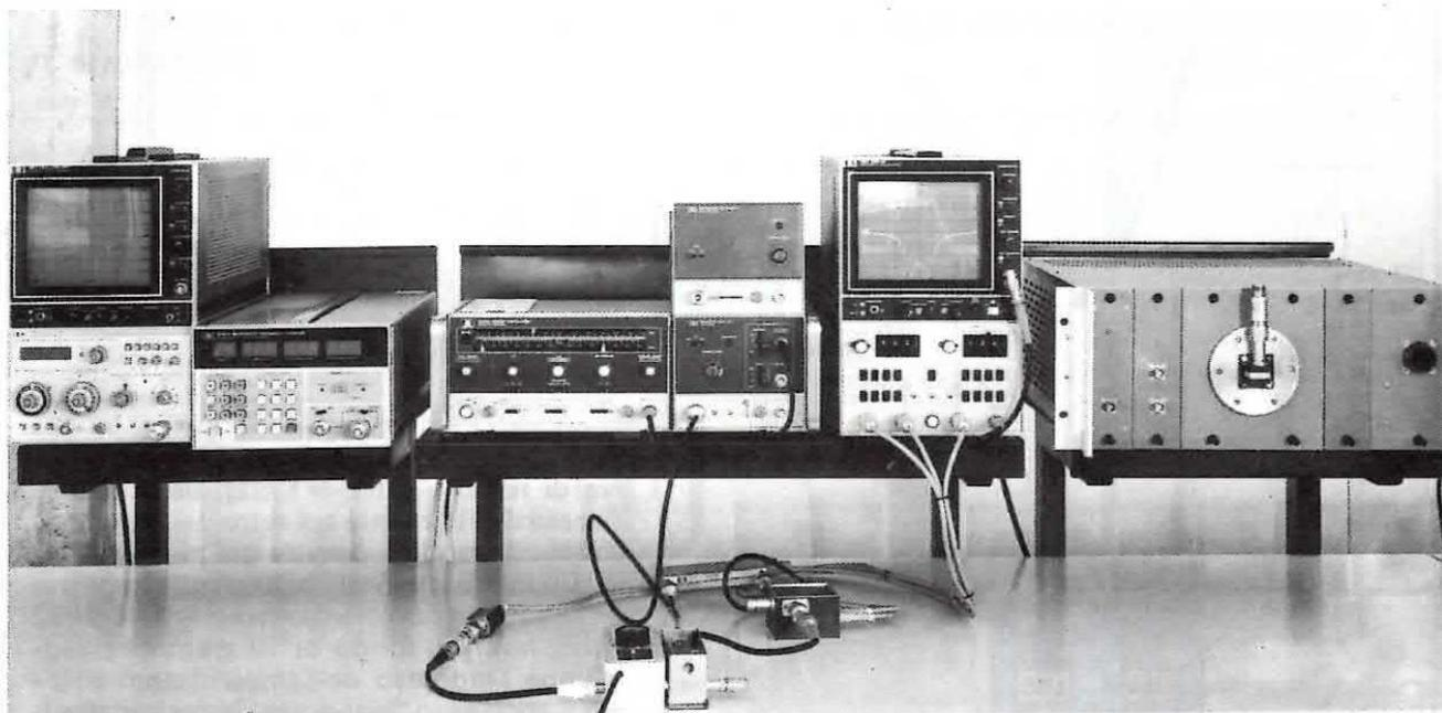
Sapere con quali attrezzature vengono controllati e collaudati i nostri progetti serve a dimostrarvi la serietà con la quale procediamo nel fornirvi i dati e le caratteristiche, che dichiariamo sulla rivista. A sinistra, il banco di controllo automatico del guadagno e della cifra di rumore di qualsiasi stadio AF, più il forno per la misura della stabilità termica al variare della temperatura. Qui sopra invece, il banco necessario ad effettuare tutte le misure per le microonde.
