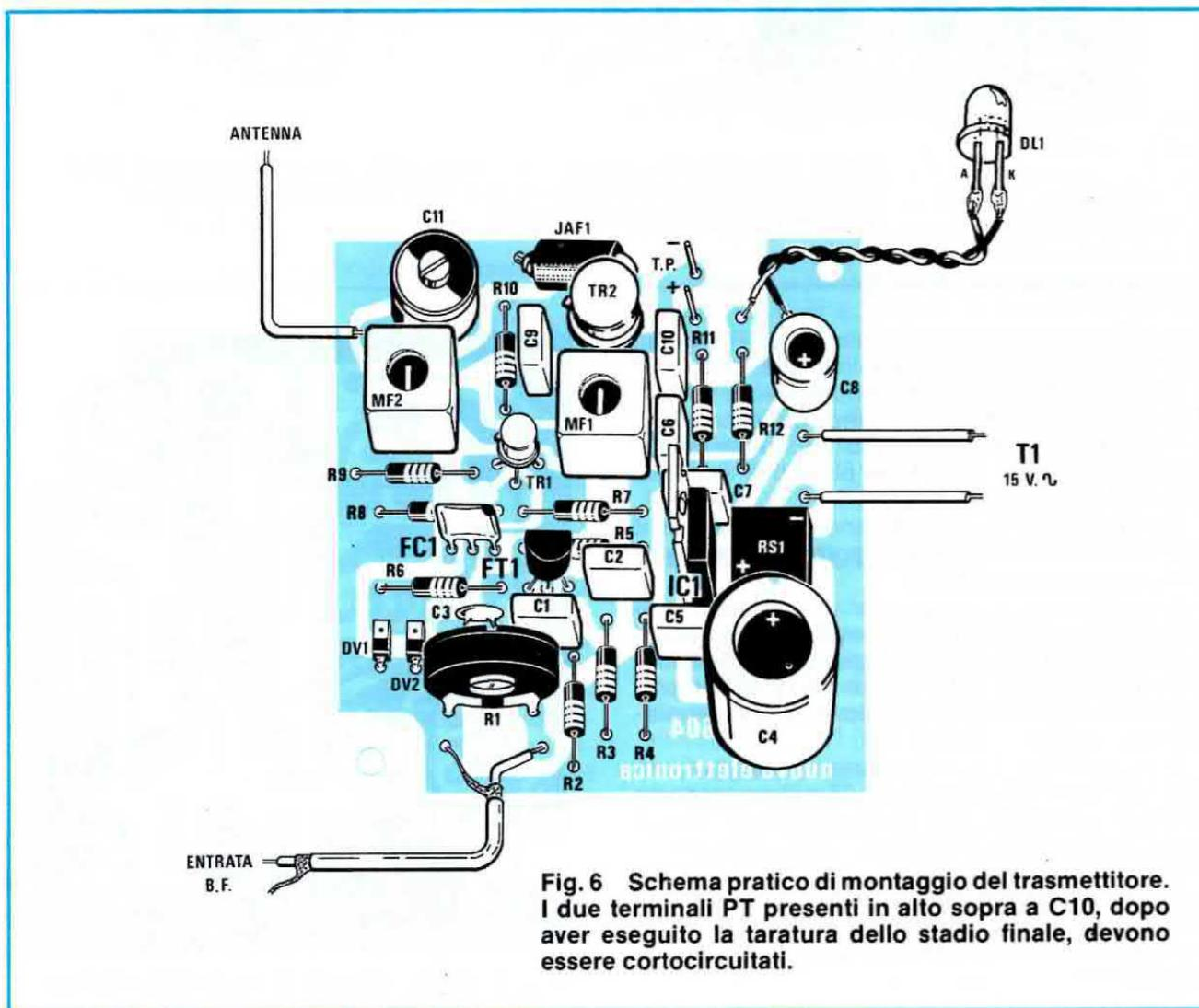
Fig. 6 Schema pratico di montaggio del trasmettitore. I due terminali PT presenti in alto sopra a C10, dopo aver eseguito la taratura dello stadio finale, devono essere cortocircuitati.
