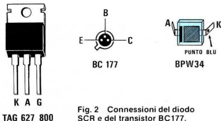
Fig. 2 Connessioni del diodo SCR e del transistor BC177.
