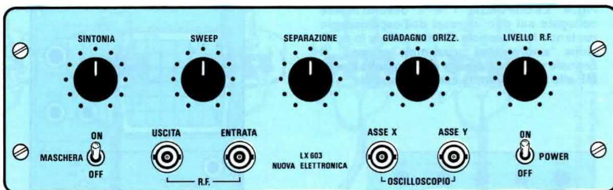
Ecco il pannello frontale del mobile dello sweep. Il potenziometro di sinistra della SINTONIA permette di portare al centro scala dell'oscilloscopio la curva campione a 455 KHz.
