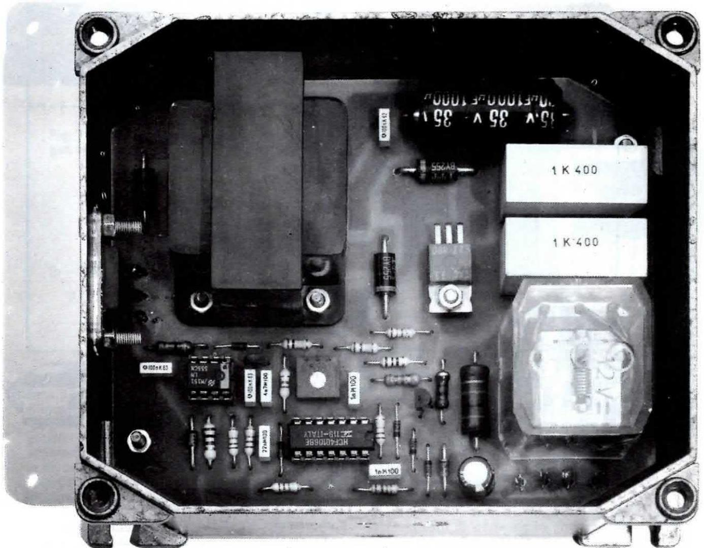
Ecco il contenitore di alluminio pressofuso a tenuta stagna appositamente scelto per contenere la nostra accensione elettronica. Il mobile è completo di coperchio a guarnizione per assicurare un'adeguata impermeabilità all'acqua. Come si può notare in questa foto il mosfet di potenza deve essere fissato direttamente sulla parete sinistra della scatola.
