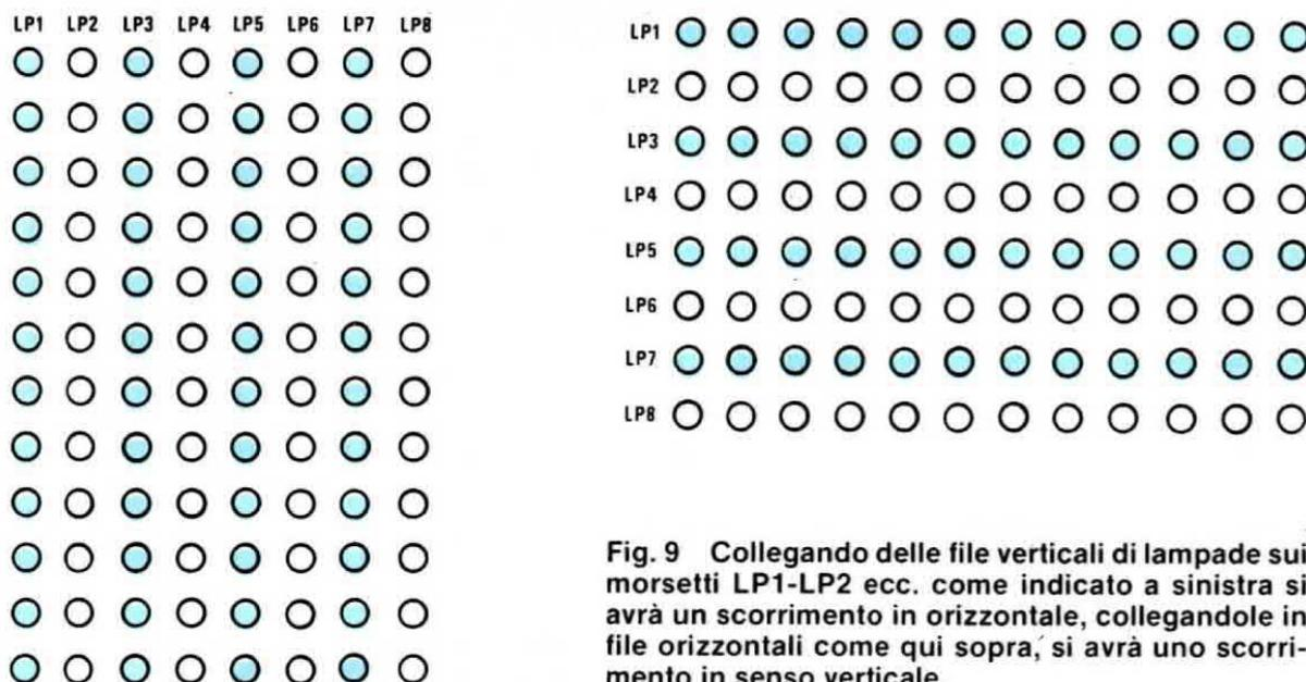
**Fig. 9** Collegando delle file verticali di lampade sui morsetti LP1-LP2 ecc. come indicato a sinistra si avrà un scorrimento in orizzontale, collegandole in file orizzontali come qui sopra, si avrà uno scorrimento in senso verticale.
