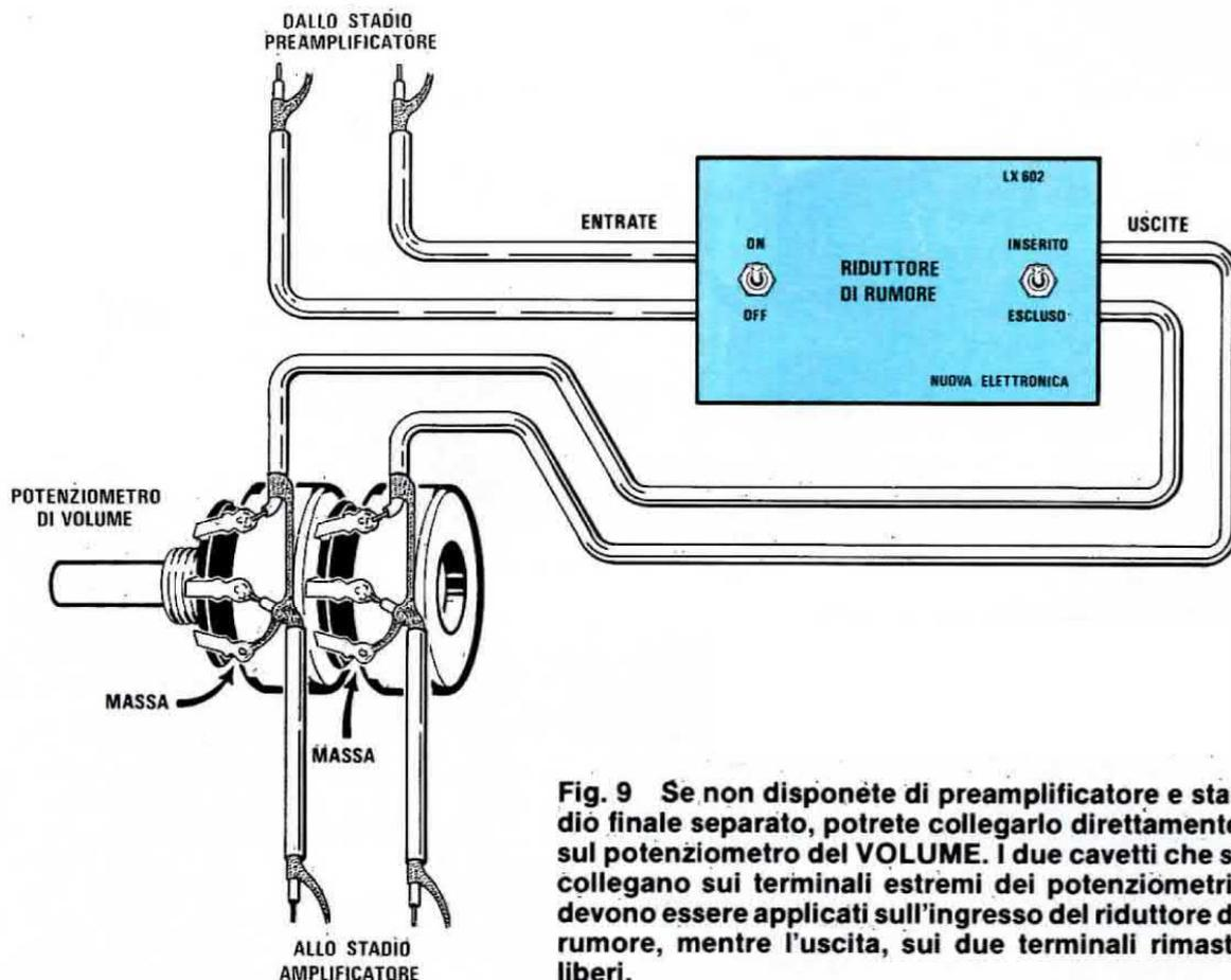
**Fig. 9** Se non disponete di preamplificatore e stadio finale separato, potrete collegarlo direttamente sul potenziometro del VOLUME. I due cavetti che si collegano sui terminali estremi dei potenziometri, devono essere applicati sull'ingresso del riduttore di rumore, mentre l'uscita, sui due terminali rimasti liberi.
