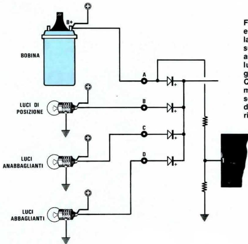
Fig. 5 Il terminale A deve essere collegato al B+ della bobina AT mentre B-C-D sui fusibili che vanno ad alimentare le lampade delle luci di posizione, abbaglianti e anabbaglianti. Questi ingressi servono per mettere in azione l'allarme se dopo aver tolto la chiave dall'auto una di queste luci rimane accesa.
