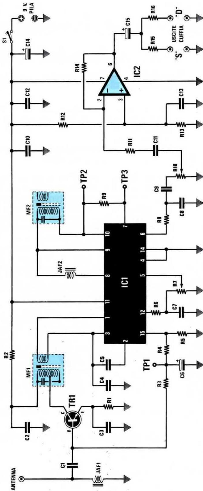
Fig. 2 Schema elettrico del ricevitore in FM sui 10,7 MHz da impiegare per ricevere il segnale del microtrasmettore di fig. 1. I terminali TP1-TP2-TP3 sono dei test-point necessari per la taratura.
