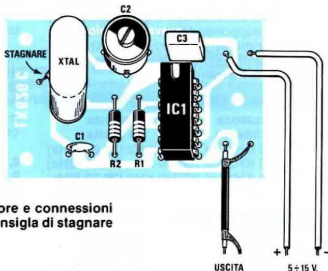
Schema pratico di montaggio dell'oscillatore e connessioni viste da sopra dell'integrato CD.4001. Si consiglia di stagnare la carcassa del quarzo a massa.
