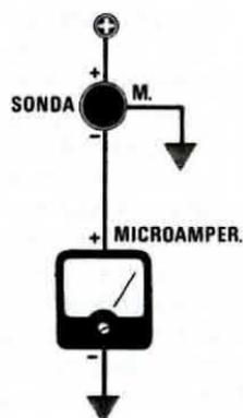
**Fig. 2** Applicando in serie all'AD.590 un microamperometro, per ogni variazione di 1 grado di temperatura noterete una variazione di corrente di 1 microamper.
