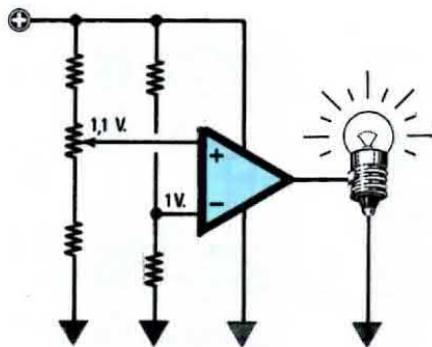
**Fig. 4** Se la tensione presente sul piedino "non invertente +" risulta leggermente superiore alla tensione presente sul "piedino invertente -", sul piedino di uscita si avrà una tensione positiva che farà ACCENDERE la lampadina.
