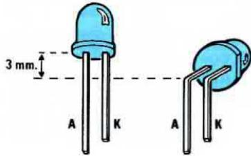
**Fig. 5** Per far fuoriuscire il corpo del diodo led dal pannello del contenitore occorre ripiegare i suoi terminali ad "L" rivolgendolo, come vedi in questo disegno, il terminale più corto (K) verso destra.
