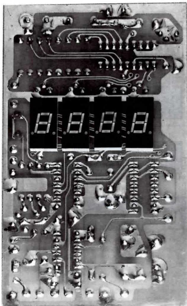
Nella foto qui sopra è visibile il circuito stampato del periodometro visto dal lato sul quale vi sono montati i quattro display. Si noti il punto decimale rivolto verso il basso.
