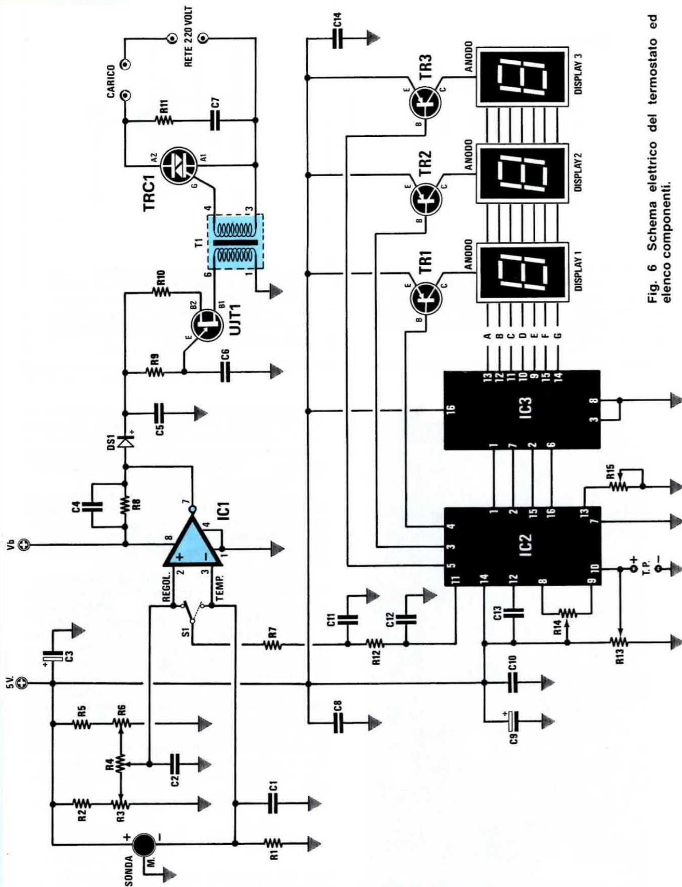
Fig. 6 Schema elettrico del termostato ed elenco componenti.
