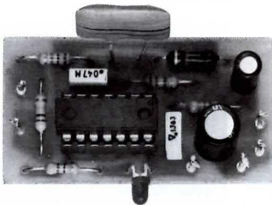
Foto del circuito del cercafili a montaggio ultimato. Si noti in alto il condensatore ceramico utilizzando come sensore e in basso il diodo led ripiegato ad "L".
