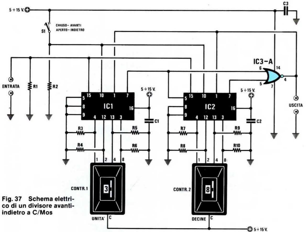
Fig. 37 Schema elettrico di un divisore avanti-indietro a C/Mos
