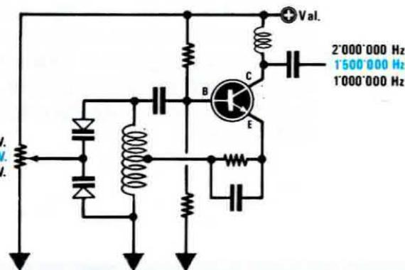
**Fig. 4** Se questo oscillatore, (applicando 2,5 volt ai diodi varicap), oscilla a 1.500.000 Hz, potremo già realizzare un semplice circuito PLL come riportato in fig. 5.
