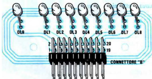
**Fig. 4** Disegno a grandezza naturale del circuito stampato da utilizzare per il montaggio dei diodi led.
