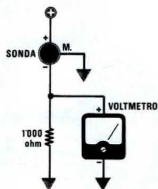
**Fig. 3** Se in serie alla sonda viene applicata una resistenza da 1.000 ohm, per ogni variazione in più o in meno di 1 grado, ai capi di tale resistenza si rileva, con un voltmetro, una variazione di tensione di 1 millivolt.
