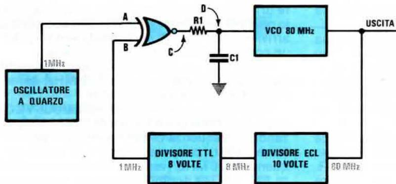
Fig. 13 Per ottenere una frequenza fissa di 80 MHz, utilizzando come frequenza di riferimento un quarzo da 1 MHz, dovremo utilizzare un divisore x10 e uno x8.
