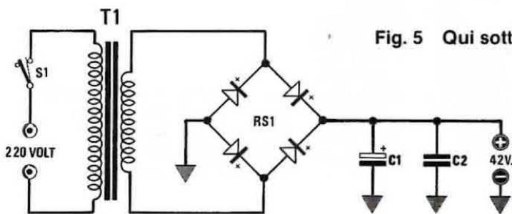
Fig. 5 Qui sotto lo schema elettrico dell'alimentatore.
