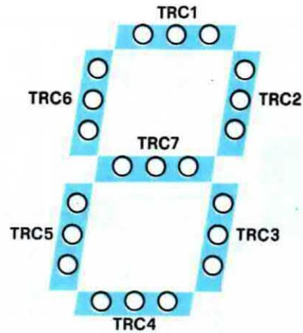
**Fig. 6** Collegando 21 lampadine, in gruppi di tre in parallelo fra loro, in uscita dei triac, TRC1-TRC2-TRC3-TRC4-TRC5-TRC6-TRC7, con la disposizione qui sopra riportata, potrete ottenere una configurazione simile ad un display a sette segmenti. In questo modo, utilizzando il programma n. 6, potrete visualizzare tutti i numeri da 0 a 9.
