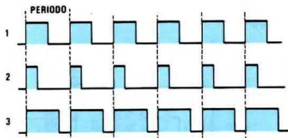
**Fig. 3** Applicando sull'ingresso A (vedi fig. 2) tre identiche frequenze, ma con forme d'onda asimmetriche (vedi 1-2-3) il frequenzimetro non valuterà tale differenza e sui display leggeremo sempre lo stesso identico periodo.
