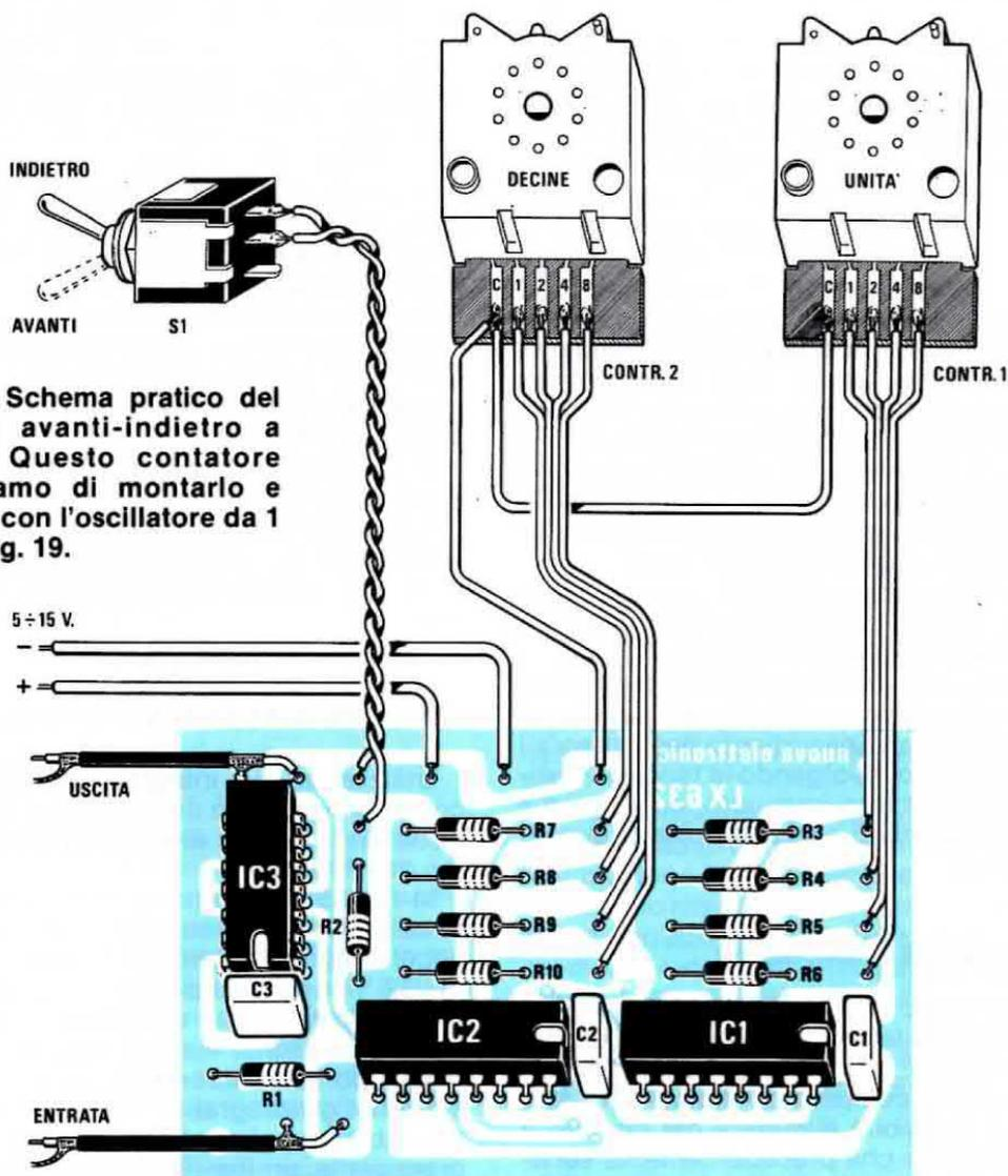
Fig. 38 Schema pratico del divisore avanti-indietro a C/Mos. Questo contatore consigliamo di montarlo e provarlo con l'oscillatore da 1 MHz di fig. 19.
