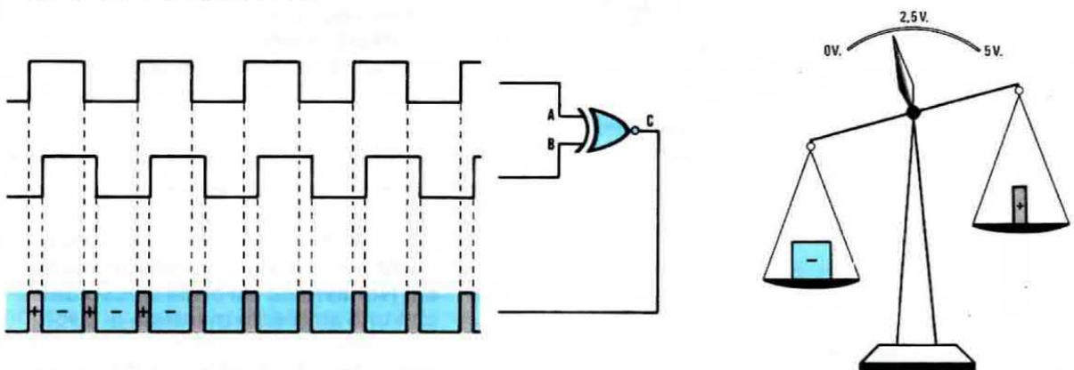
**Fig. 9** Se la frequenza del VCO da 1.500.000 Hz aumentasse anche di un solo hertz passando così a 1.500.001 Hz, otterremmo un effetto opposto a quello di fig. 8, cioè sull'uscita del Nor ritroveremmo un'onda quadra in cui la semionda positiva risulta più STRETTA della semionda negativa. Risultando il "peso" negativo maggiore di quello positivo, la tensione sul condensatore diminuirà.
