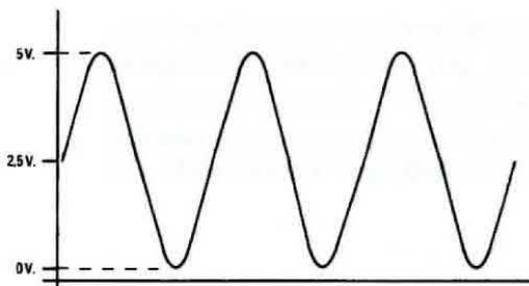
**Fig. 3** Se l'ampiezza del segnale da 100 Hz raggiunge un massimo di 5 volt positivi, il condensatore del filtro passa-basso (vedi fig. 2) si caricherà e si scaricherà da 0 a 5 volt alla frequenza di 100 Hz. Questa tensione, come spiegato, servirà per alimentare i diodi varicap posti sulla bobina dell'oscillatore variabile.
