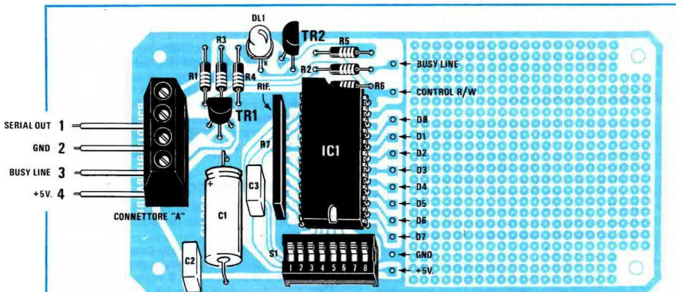
**Fig. 9** Schema pratico di montaggio della scheda universale che potrete completare con i più svariati circuiti sperimentali di vostra progettazione.
