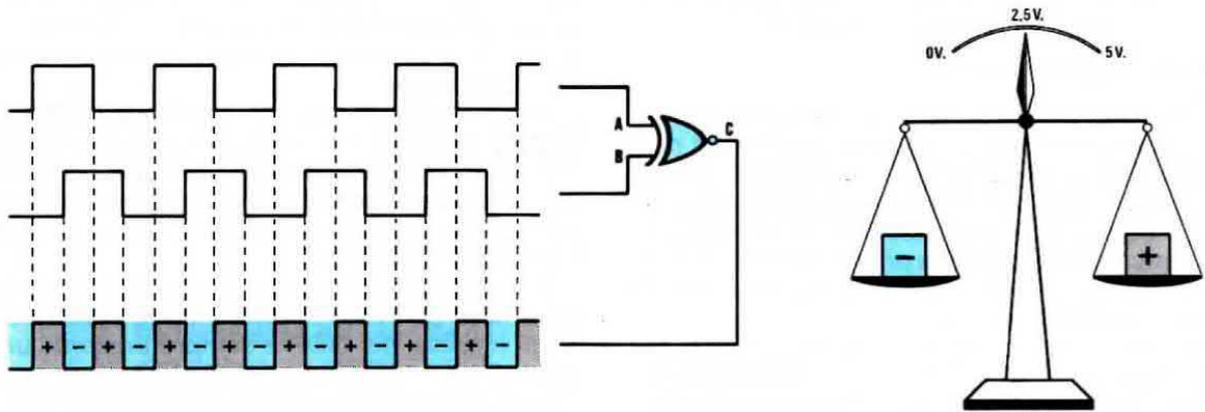
**Fig. 7** Quando la frequenza presente sull'ingresso A risulta sfasata di 90° gradi rispetto a quella applicata sull'ingresso B, in uscita del Nor avremo un'onda quadra in cui la larghezza della semionda positiva risulta perfettamente identica a quella della semionda negativa e quindi, risultano identici di due "pesi", la tensione presente sul condensatore del filtro passa-basso si stabilizzerà sul valore richiesto.
