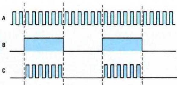
Fig. 2 Applicando sull'ingresso A la differenza di un quarzo da 1 MHz e utilizzando, per gli impulsi di "start" e "stop", la frequenza da leggere, in questo tempo vengono conteggiati quanti impulsi della frequenza da 1 MHz riescono a raggiungere i contatori.
