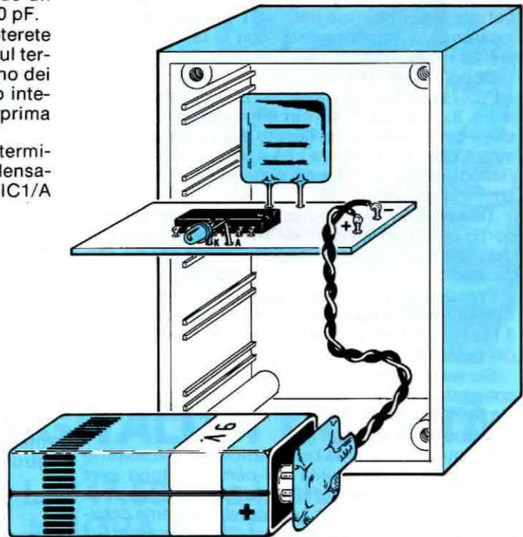
**Fig. 6** Il circuito stampato come vedi in questo disegno e nella foto di sinistra deve essere infilato verticalmente nelle due guide presenti all'interno del mobile. Di lato il piano di foratura del pannello di alluminio.
