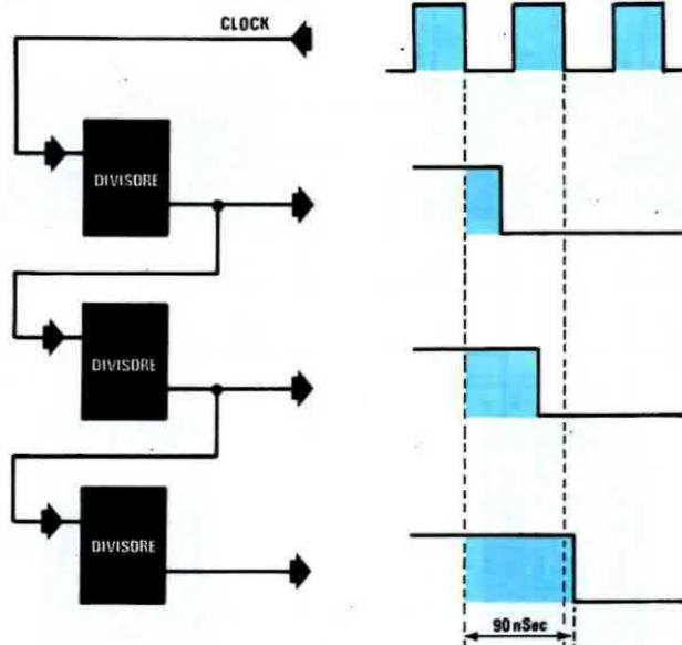
Fig. 30 Utilizzando dei divisori asincroni, poichè l'impulso della frequenza da dividere dal primo divisore passa al secondo divisore, il tempo di ritardo di propagazione viene sommato ad ogni passaggio, quindi, più stadi divisori aggiungiamo, minore risulterà la frequenza massima che potremo applicare sull'ingresso, perchè il contatore non perda dei clock. Per questo motivo molti notano una differenza fra la frequenza generata e la frequenza impostata sui commutatori binari.
