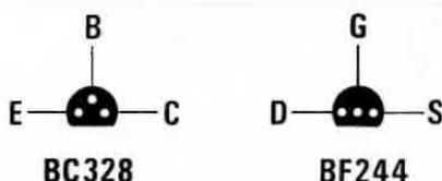
Fig. 7 Connessioni viste da sotto del transistor e del fet utilizzati per la realizzazione di questi due preamplificatori di bassa frequenza.
