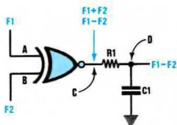
Fig. 1 Applicando sugli ingressi A-B di un Nor Esclusivo due diverse frequenze sull'uscita C ci ritroveremo una frequenza pari alla somma di  $F1+F2$  e un'altra frequenza ricavata sottraendo  $F1-F2$ . Dopo il filtro passa-basso composto da R1-C2 risulterà presente solo la frequenza più bassa, cioè  $F1-F2$ .
