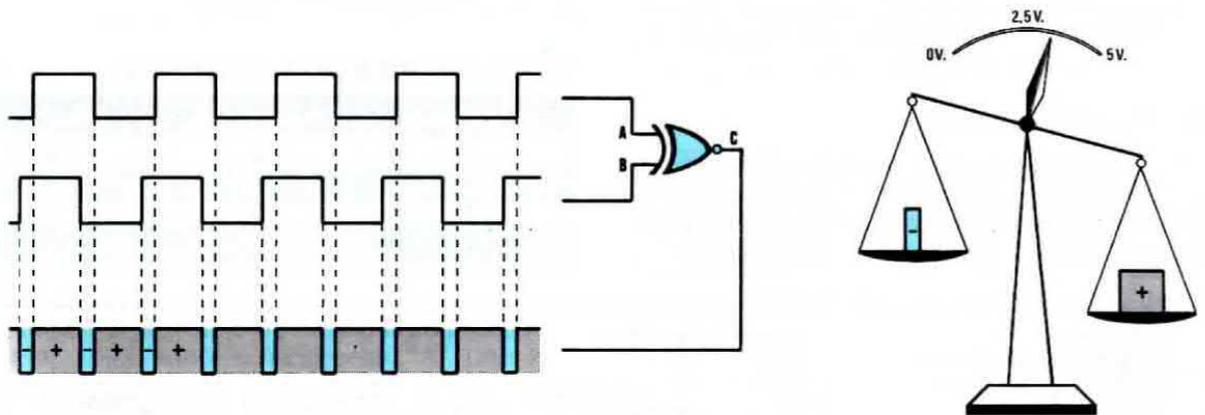
**Fig. 8** Se la frequenza del VCO, applicata sull'ingresso B, tendesse a slittare e passare così da 1.500.000 Hz a 1.499.999 Hz, la differenza di fase sui due ingressi si modificerebbe e in uscita del Nor ritroveremmo un'onda quadra in cui la semionda positiva risulta più LARGA della semionda negativa. Risultando il "peso" positivo maggiore del negativo, la tensione sul condensatore aumenterà.
