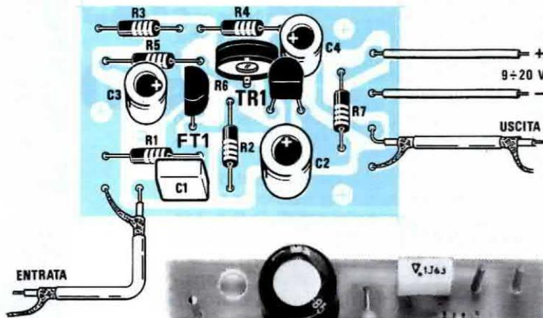
Fig. 6 Schema pratico di montaggio del preamplificatore con fet + transistor riportato in fig. 2. Di lato la foto del preamplificatore montato.
