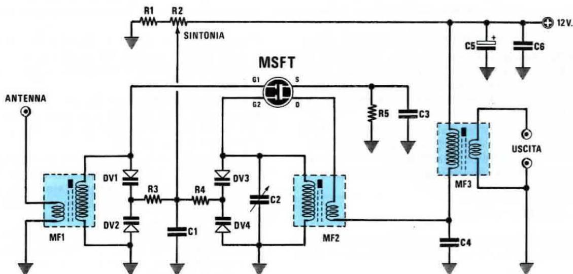
Fig. 1 Schema elettrico ed elenco componenti.
