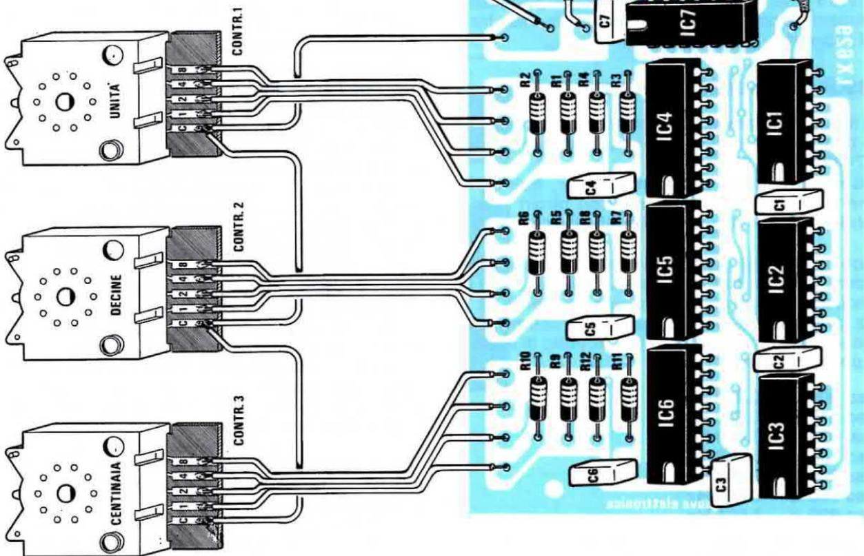
**Fig. 27** Schema pratico di montaggio del circuito riportato in fig. 26. Nel kit, per ogni integrato, troverete il relativo zoccolo da inserire nel circuito stampato.
