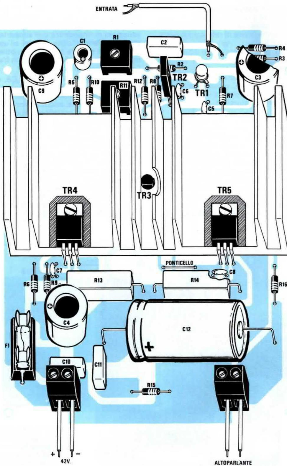
Fig. 3 Schema pratico di montaggio dell'amplificatore Hi-Fi da 15-30 watt. Ricordatevi che TR4 deve essere montato a sinistra mentre TR5 a destra. Si notino le miche isolanti presenti sotto il corpo dei due finali.
