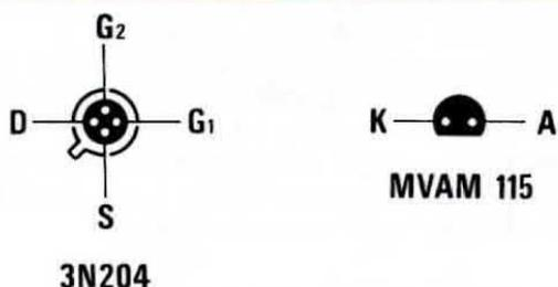
Fig. 4 Connessioni viste da sotto del mosfet e del diodo varicap utilizzati in tale progetto. Vedere in fig. 2 da quale lato è disposta la parte piana di tali diodi.
