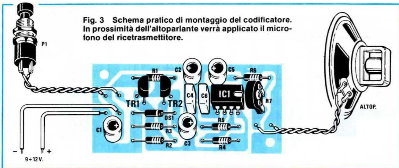
Fig. 3 Schema pratico di montaggio del codificatore. In prossimità dell'altoparlante verrà applicato il microfono del ricetrasmittitore.
