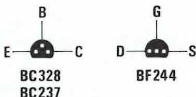
Tutti i componenti, compreso commutatore e potenziometri vengono montati su un unico circuito stampato siglato LX.609. Di lato le connessioni dei transistor e dei fet utilizzati in tale montaggio viste da sotto.
