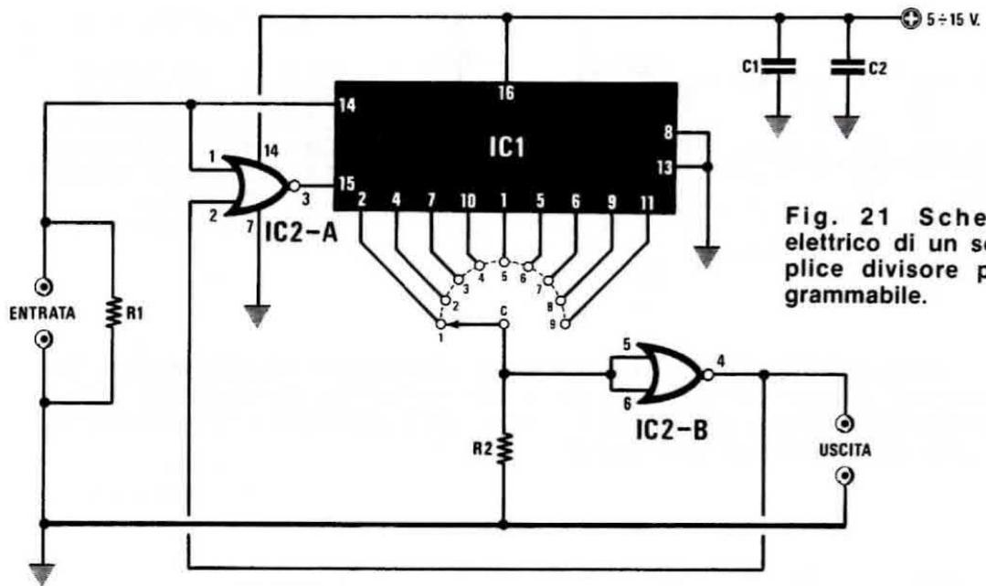
Fig. 21 Schema elettrico di un semplice divisore programmabile.
