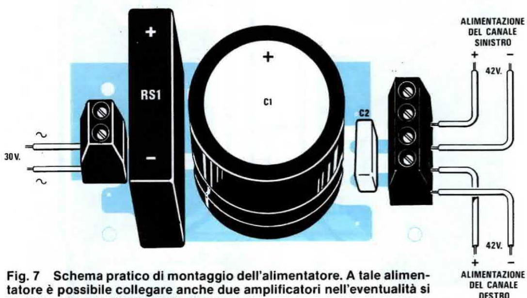
Fig. 7 Schema pratico di montaggio dell'alimentatore. A tale alimentatore è possibile collegare anche due amplificatori nell'eventualità si voglia realizzare un impianto stereo.
