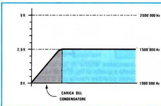
Fig. 6 Infatti fino a quando la differenza tra F1 e F2 è elevata, in uscita dal Nor avremo un'onda sinusoidale con una ampiezza massima di 5 volt, che caricando il condensatore farà aumentare la frequenza del VCO. Quando, a 2,5 volt, il VCO oscillerà a 1.500.000 Hz, risultando questa frequenza identica a quella del quarzo, in uscita avremo una frequenza di  $1.500.000 - 1.500.000 = \emptyset$  Hz.
