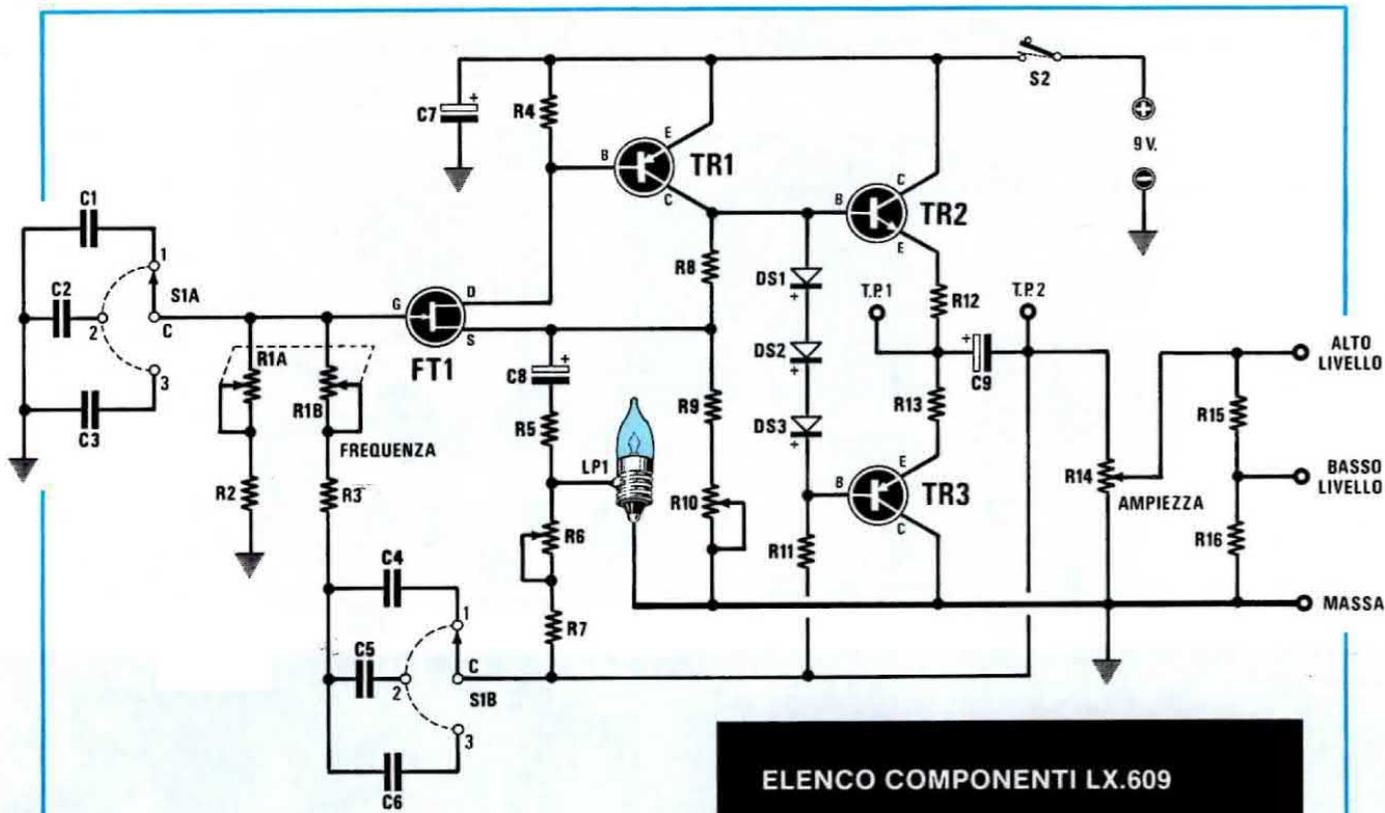
Fig. 1 Schema elettrico dell'oscillatore di BF.
