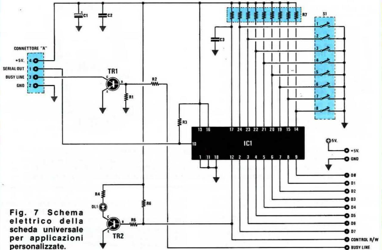
**Fig. 7** Schema elettrico della scheda universale per applicazioni personalizzate.
