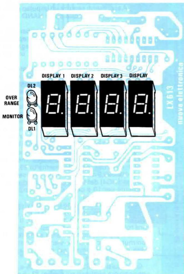
**Fig. 7** Sul lato opposto del circuito stampato visibile in fig. 6 monterete i due diodi led e i quattro display, posizionandoli in modo che il punto decimale sia rivolto verso il basso.
