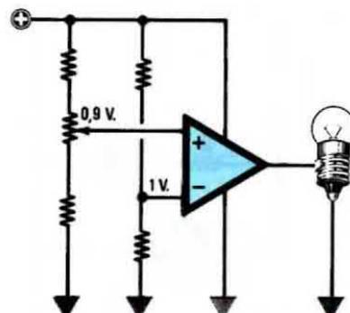
**Fig. 5** Nello stesso comparatore, se la tensione presente sul piedino "non invertente +" è minore della tensione presente sul piedino "invertente -", sul piedino di uscita si avrà tensione 0 quindi la lampadina rimarrà SPENTA.
