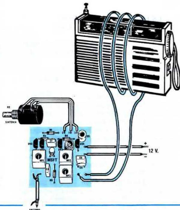
Proseguite, inserendo il compensatore ceramico ed i quattro diodi varicap DV1-DV2-DV3-DV4.
