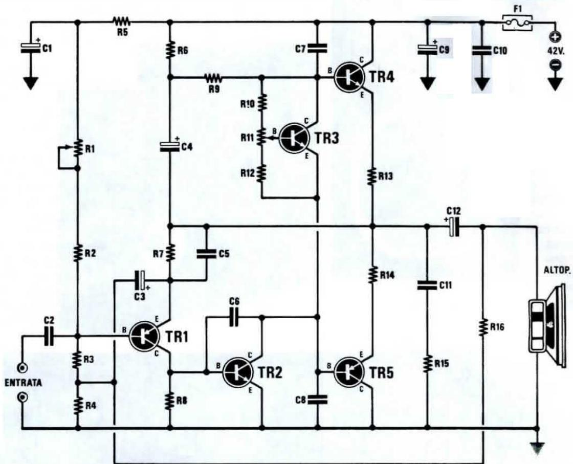
Fig. 1 Schema elettrico.
