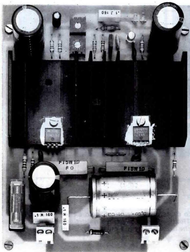
Come si presenta a montaggio ultimato l'amplificatore descritto in articolo. Si noti al centro dell'aletta di raffreddamento il corpo del transistor TR3 e agli estremi dell'aletta i due darlington di potenza BDX53 e DBX54 con i terminali ripiegati ad L. Non dimenticate di porre sotto ai due finali la mica isolante inserita nel kit.
