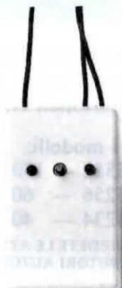
La scatola in plastica antiurto contenente il circuito dell'interfaccia cassetta è di colore avorio e, come vedesi nella foto andrà innestata direttamente sul connettore presente sul retro del Commodore. Con tale interfaccia potrete ora utilizzare sul vostro computer qualsiasi registratore mangianastro.
