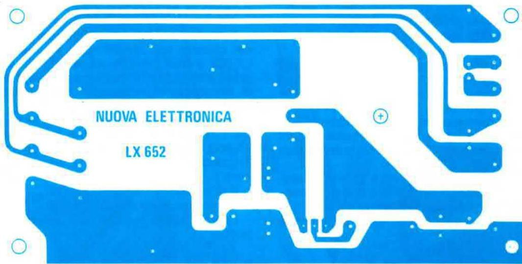
Fig. 7 Disegno a grandezza naturale del circuito stampato richiesto per la realizzazione dello schema di fig. 5.
