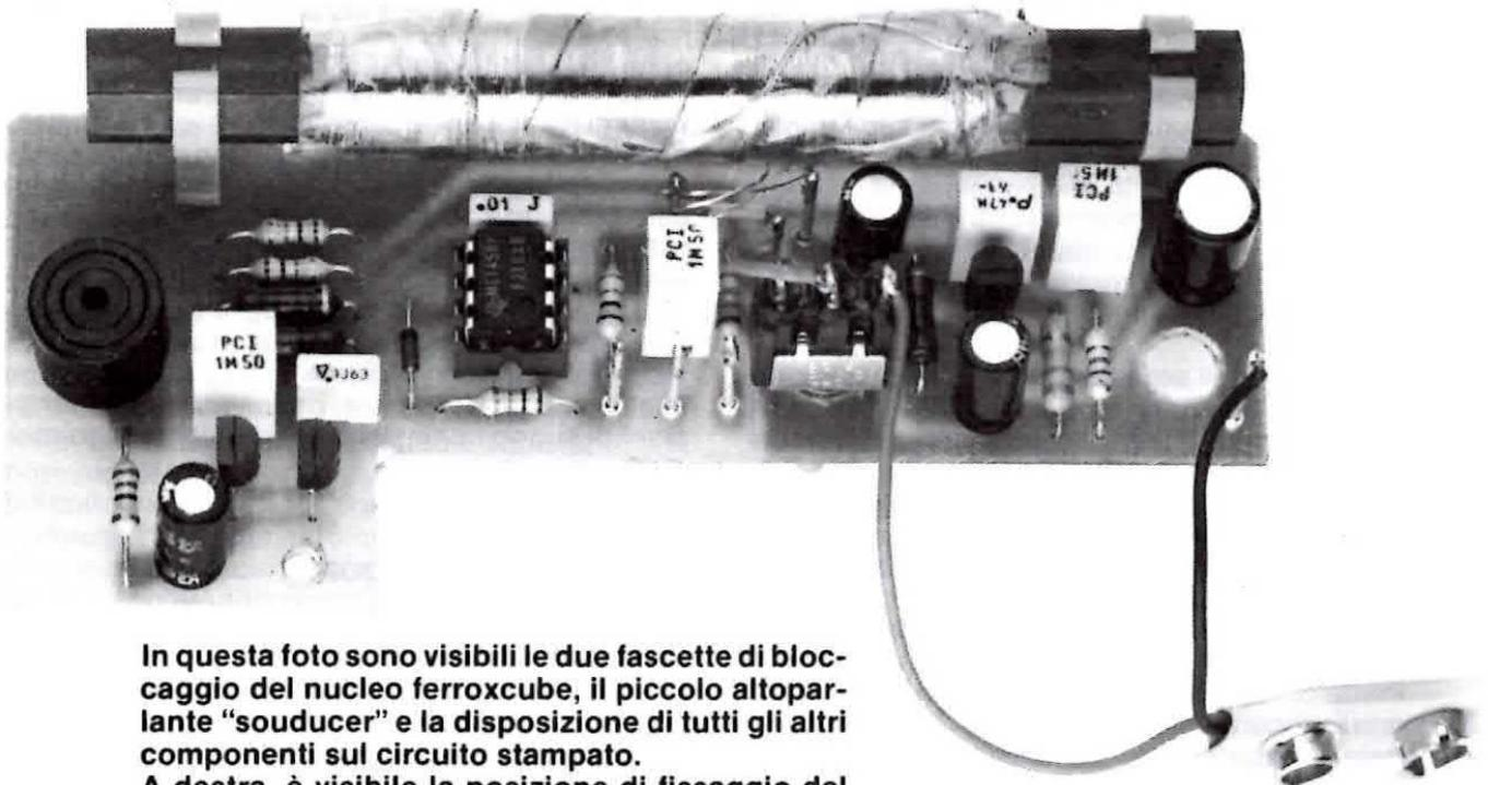
In questa foto sono visibili le due fascette di bloccaggio del nucleo ferrocubo, il piccolo altoparlante "souducer" e la disposizione di tutti gli altri componenti sul circuito stampato.
