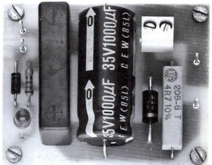
**Foto dell'alimentatore a tampone richiesto per i modelli di computer Commodore la cui presa di alimentazione è costituita da una normale spina bipolare. Per gli altri modelli vedere lo schema riportato in fig. 5.**
