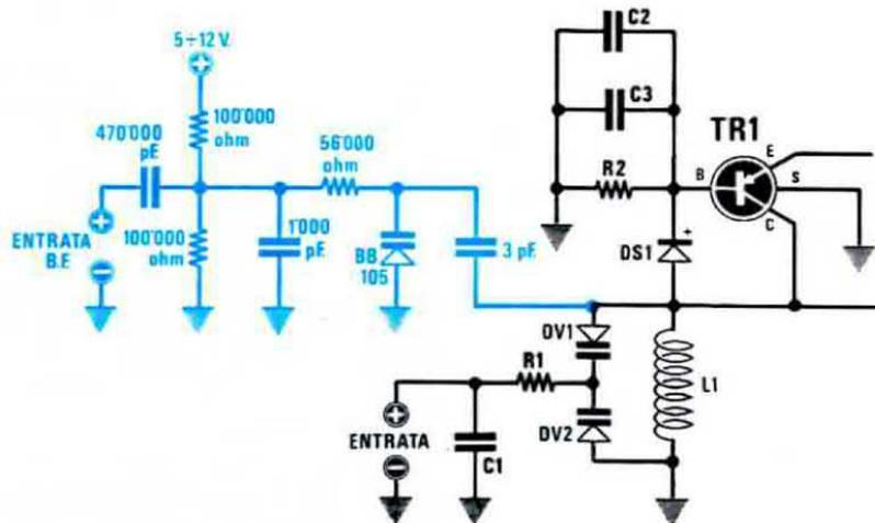
**Fig. 15** Per modulare un sintetizzatore PLL in FM conviene sempre utilizzare un altro diodo varicap tipo BB.105 o equivalente che collegherete alla bobina del VCO tramite un piccolo condensatore ceramico da 3-4 pF. Il diodo varicap BB.105 lo dovrete sempre polarizzare, come vedesi in figura, con due resistenze da 100.000 ohm.
