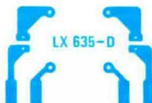
Fig. 22 Disegno a grandezza naturale del circuito stampato, richiesto per il montaggio dei diodi, come visibile in fig. 21.
