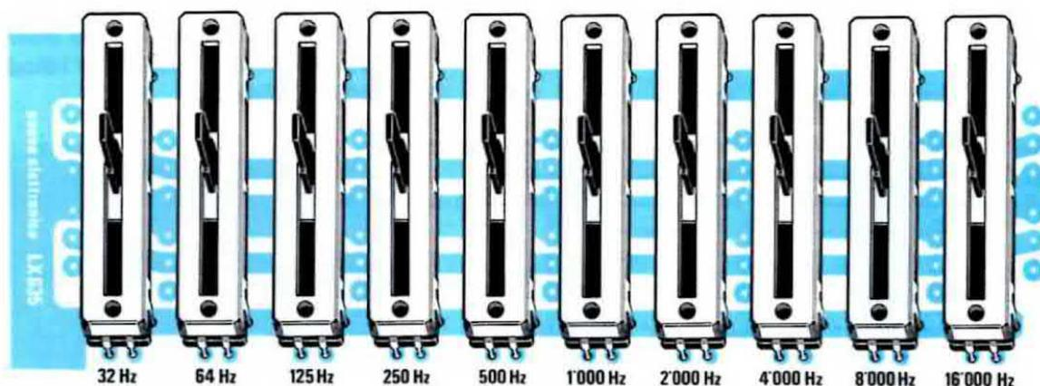
**Fig. 8** Tutti i dieci potenziometri a slitta da 22.000 ohm lineari, andranno fissati sul circuito stampato a fori metallizzati siglato LX.635. Nel disegno abbiamo riportato anche le frequenze su cui agisce ogni potenziometro.
