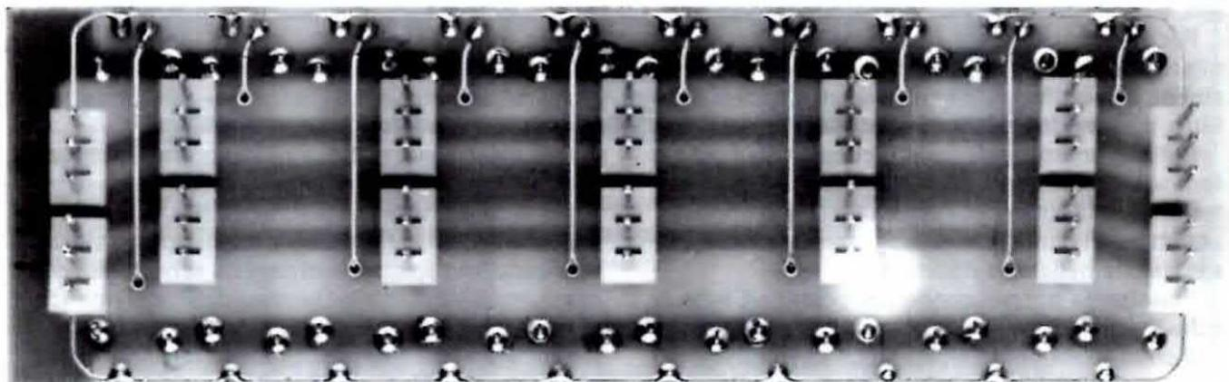
**Dal lato opposto di questo stesso circuito, dovrete fissare i connettori maschi, utili per innestare le cinque schede dei filtri, più quella del preamplificatore/equalizzatore, che potrà essere inserita indifferentemente sui due connettori esterni.**
