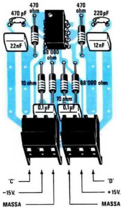
**Fig. 20** Schema pratico di montaggio dell'ultimo doppio filtro, relativo alla frequenza di 8.000-16.000 Hz. Inserendo l'integrato TL.082, controllate sempre che il "punto" di riferimento risulti rivolto in alto.
