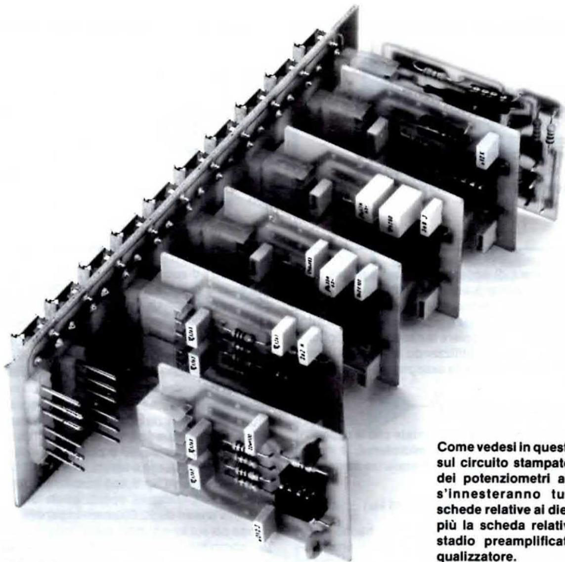
Come vedesi in questa foto, sul circuito stampato base dei potenziometri a slitta, s'innesteranno tutte le schede relative ai dieci filtri più la scheda relativa allo stadio preamplificatore/equalizzatore.
