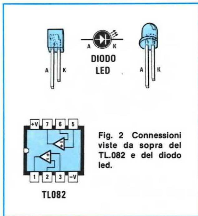
Fig. 2 Connessioni viste da sopra del TL082 e del diodo led.
