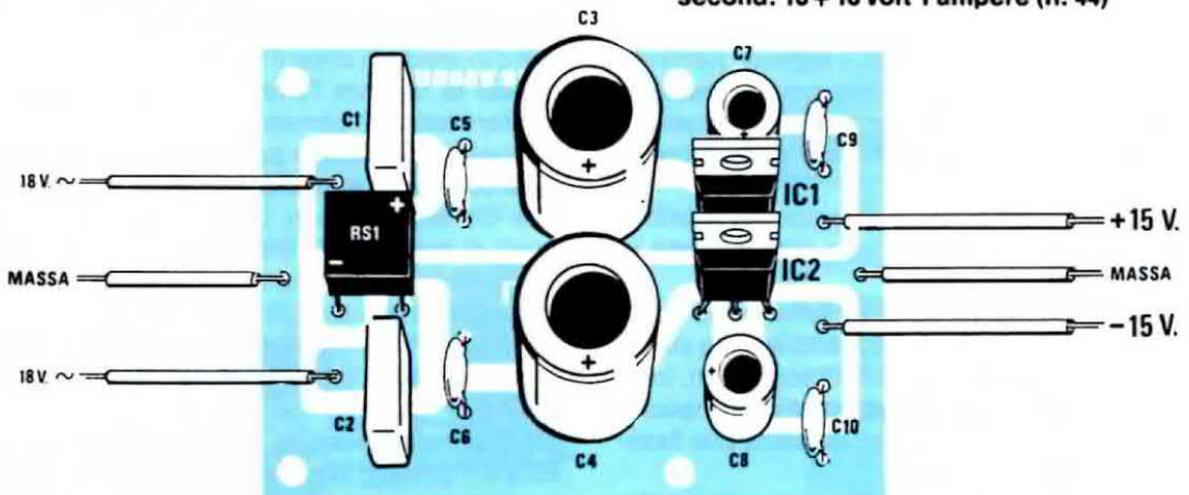
Fig. 30 Schema pratico di montaggio dell'alimentatore duale.
