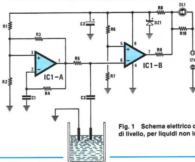
Fig. 1 Schema elettrico dell'Indicatore di livello, per liquidi non infiammabili.
