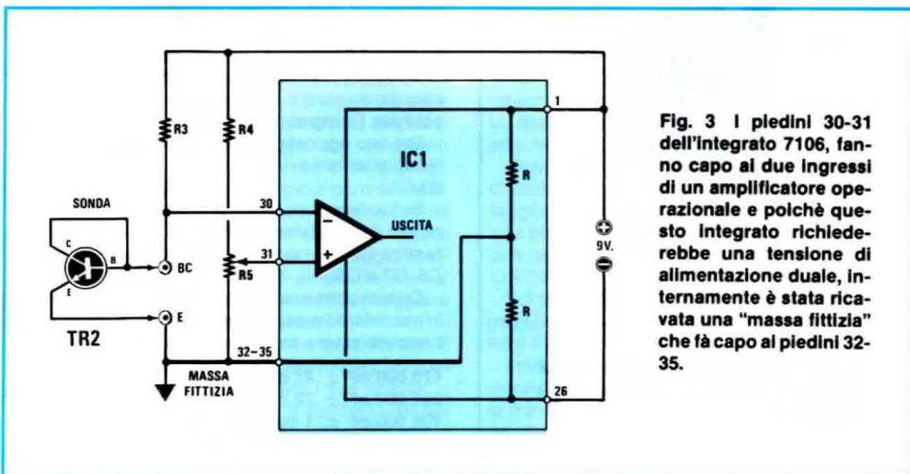
Fig. 3 I piedini 30-31 dell'integrato 7106, fanno capo ai due ingressi di un amplificatore operazionale e poiché questo integrato richiederebbe una tensione di alimentazione duale, internamente è stata ricavata una "massa fittizia" che fa capo ai piedini 32-35.
