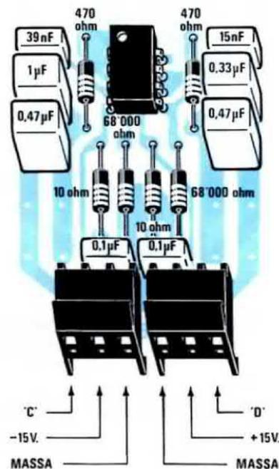
**Fig. 17** Schema pratico di montaggio del secondo doppio filtro, relativo alla frequenza di 125-250 Hz. Anche per tale scheda, abbiamo utilizzato più condensatori posti in parallelo, per ottenere i valori richiesti.
