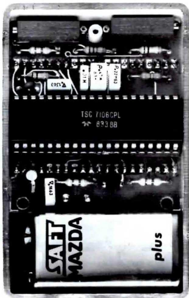
Come vedesi in questa foto, il circuito verrà posto all'interno della scatola in plastica ed a questa, fissato con due viti autofilettanti. In basso potrete collocare la pila di alimentazione da 9 volt.
