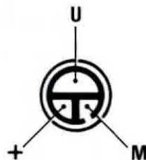
**Fig. 12** Se mancano questi fili, controllate attentamente le tre piste: una di queste è sempre collegata al metallo esterno del microfono (filo M) e, utilizzandola come riferimento, a sinistra troverete il + e a destra l'uscita di BF (filo U).
