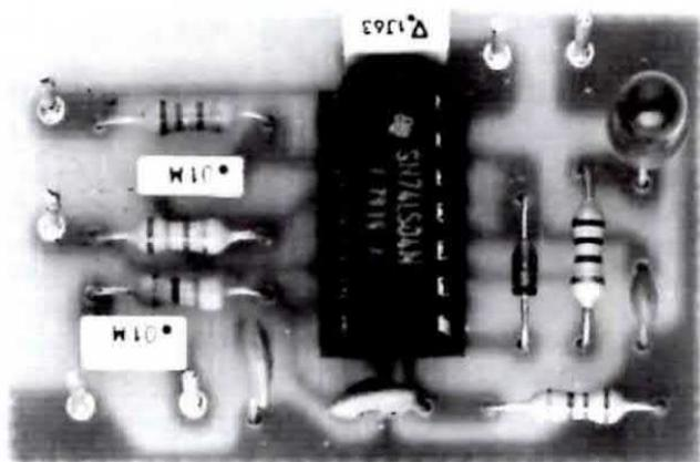
Sulla sinistra, la foto ingrandita del circuito già montato che ci permetterà di controllare qualsiasi quarzo sia in fondamentale che in overtone da un minimo di 0,1 MHz ad un massimo di 150 MHz.
