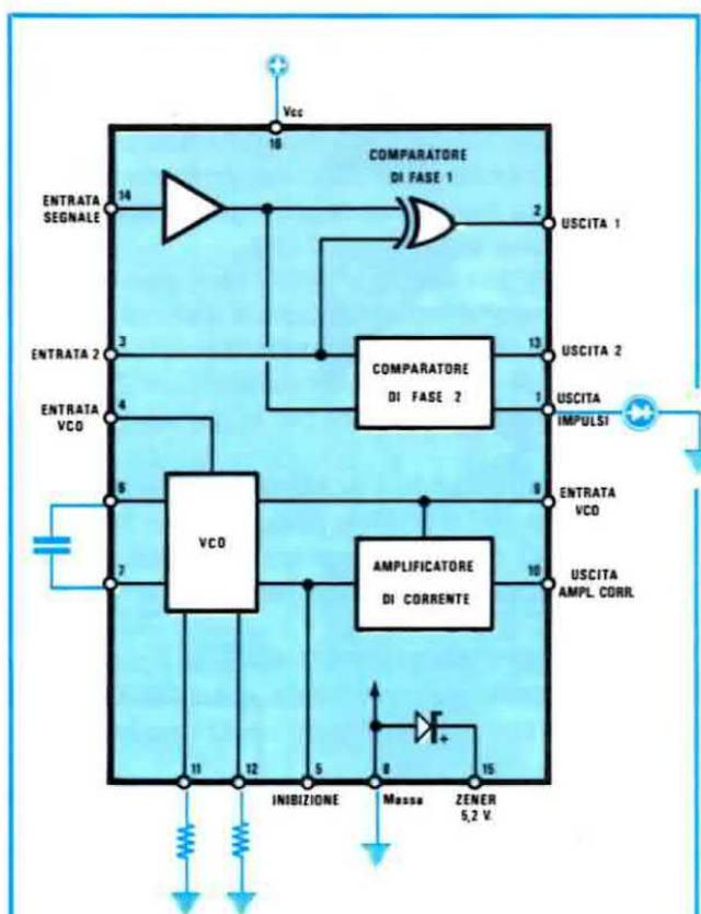
**Fig. 3** In tutti gli schemi che proporremo, anziché utilizzare un Or Esclusivo impiegheremo sempre l'integrato CD.4046 perché, nel suo interno, è presente un circuito più completo che funziona sia da comparatore di Fase che di Frequenza.
