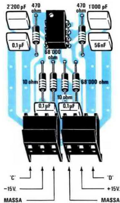
**Fig. 19** Schema pratico di montaggio del quarto doppio filtro, relativo alla frequenza di 2.000-4.000 Hz. In tale scheda le capacità richieste per C9-C8 e di C12-C11 risultano tutte di valore standard.
