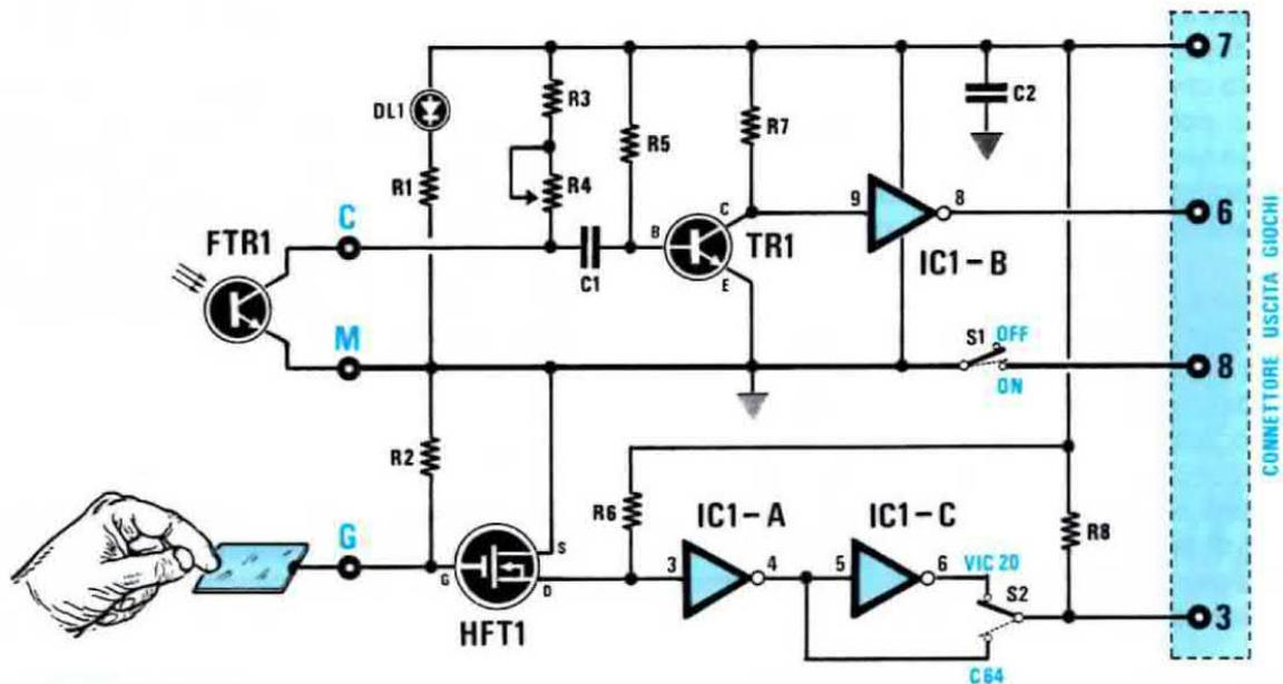
**Fig. 1** Schema elettrico del circuito che vi permetterà di disegnare, sul video del vostro computer VIC.20 o C.64. Per adattare il circuito a questi due tipi di computer, è sufficiente spostare soltanto il deviatore S2.
