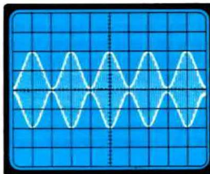
**Fig. 4** Aumentando l'ampiezza del segnale BF, avrete una maggiore variazione di tensione e di conseguenza un aumento dell'ampiezza del segnale di AF.
