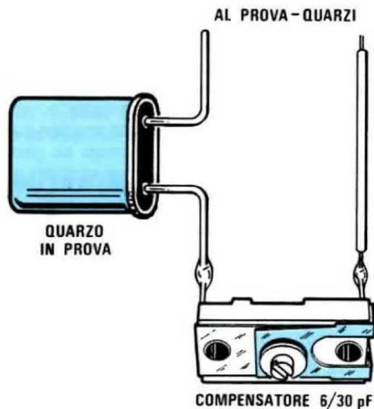
Fig. 7 Misurando la frequenza di un quarzo, questa risulterà sempre leggermente diversa da quella riportata sull'involucro. Collegando in serie un piccolo compensatore, come vedesi in figura, si riuscirà a correggere questa differenza e questo potrete facilmente constatarlo se disponete di un frequenzimetro digitale.
