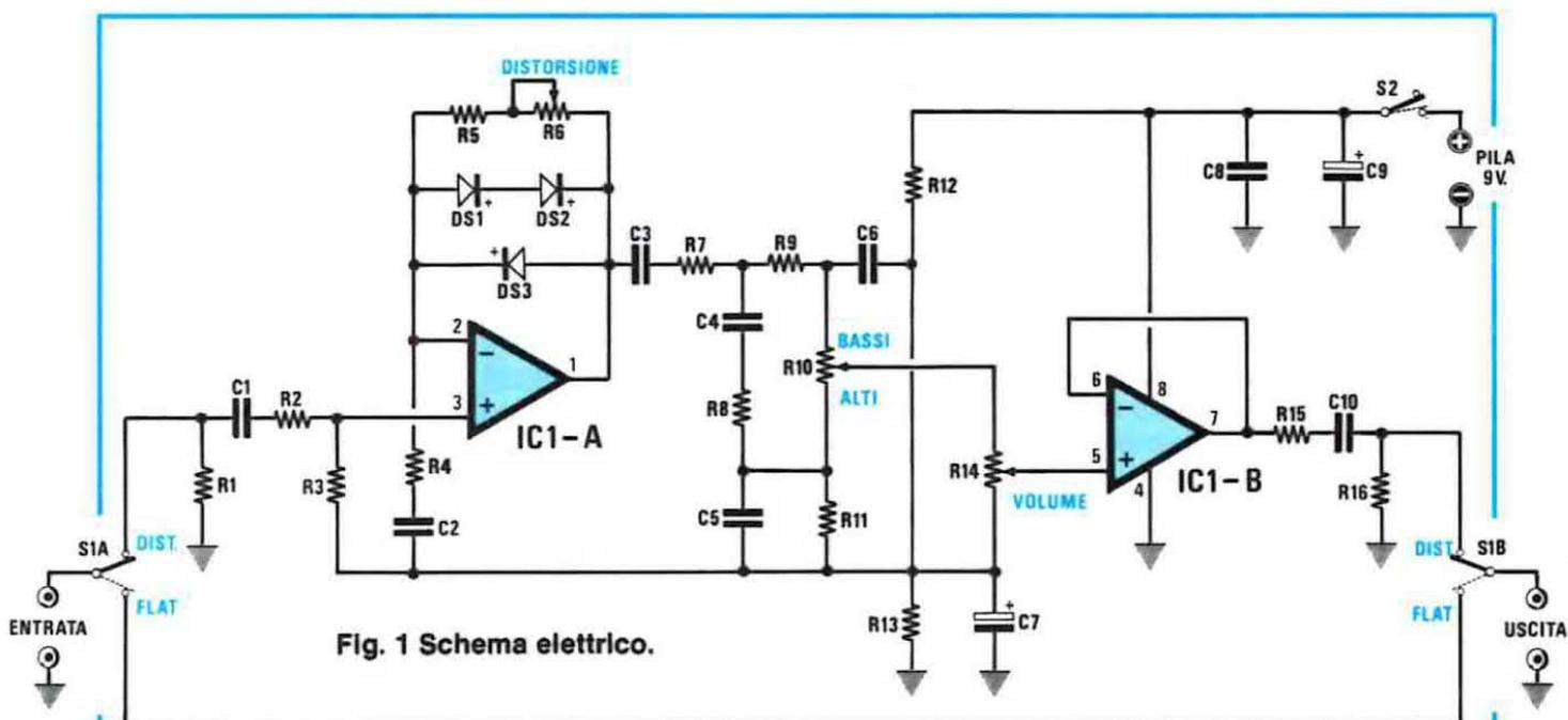
Fig. 1 Schema elettrico.
