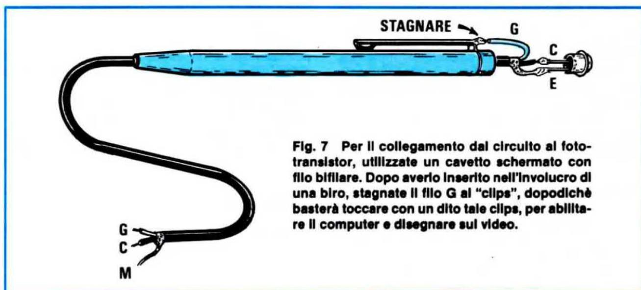
**Fig. 7** Per il collegamento dal circuito al fototransistor, utilizzate un cavetto schermato con filo bifilare. Dopo averlo inserito nell'involucro di una biro, stagnate il filo G ai "clips", dopodichè basterà toccare con un dito tale clips, per abilitare il computer e disegnare sul video.
