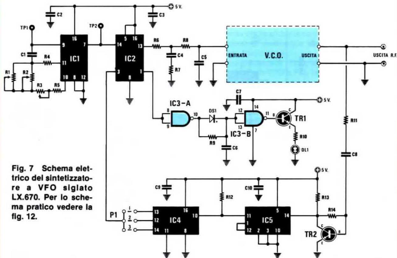
Fig. 7 Schema elettrico del sintetizzatore a VFO siglato LX.670. Per lo schema pratico vedere la fig. 12.
