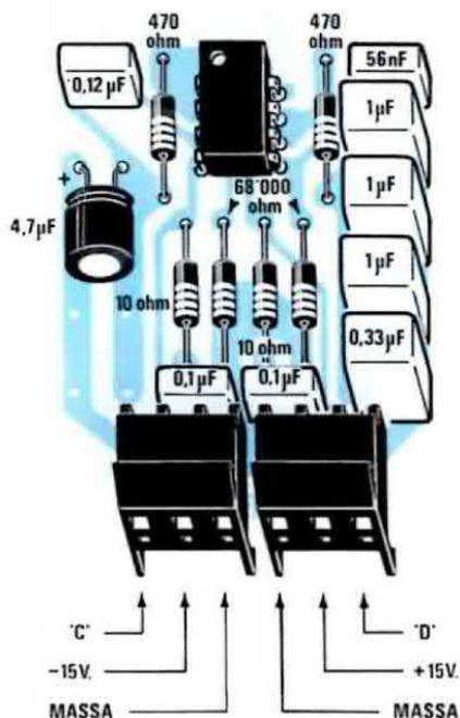
**Fig. 16** Schema pratico di montaggio del doppio filtro, relativo alla frequenza di 32-64 Hz. Per ottenere le capacità richieste per C9-C8 e C12-C11 abbiamo utilizzato, come vedesi in disegno, più capacità poste in parallelo.
