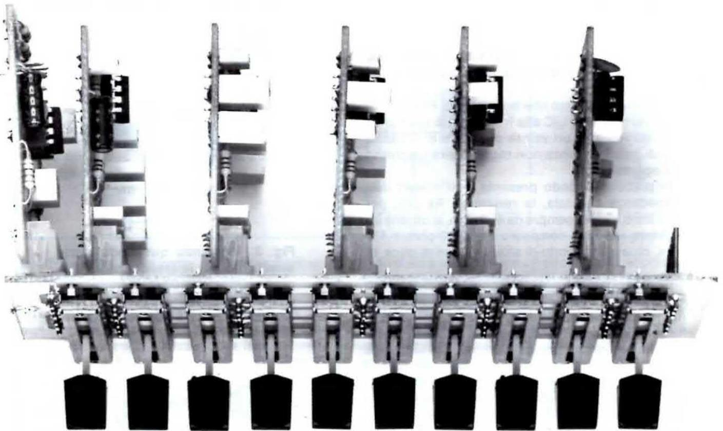
In questa foto sono visibili i dieci potenziometri che controllano le frequenze di centro banda di 32 - 64 - 125 - 250 - 500 - 1.000 - 2.000 - 4.000 - 8.000 - 16.000 Hz, le cinque schede dei filtri, più la scheda dello stadio preamplificatore/egualizzatore, che potrete inserire indifferentemente sul connettore di destra o di sinistra. Vi ricordiamo che ogni scheda filtro controlla due frequenze.
