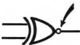
Fig. 1 Negli articoli precedenti, è apparso in ogni disegno il simbolo del Nor, provvisto, sull'uscita, di un piccolo cerchietto.
