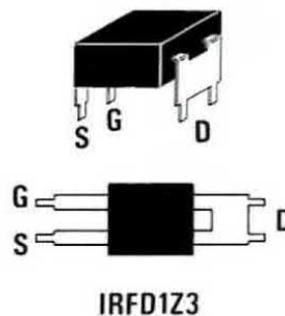
**Fig. 3** Connessioni G-D-S, dell'Hexfet IRFD.1Z3, impiegate per la realizzazione di questa penna ottica.
