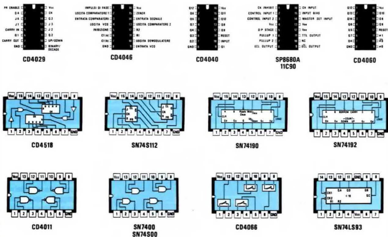
**Fig. 10** Tutte le connessioni degli integrati, viste da sopra, e dei due transistor visti invece da sotto, impiegati nei diversi progetti di sintetizzatori PLL presentati in questo articolo.
