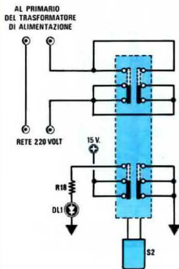
**Fig. 9** Schema elettrico del circuito di commutazione rete e flat-equalizzazione, che dovrà essere montato sul circuito stampato siglato LX.635/C. È importante innestare completamente a fondo i due commutatori, altrimenti uno potrebbe trovarsi più in basso dell'altro.
