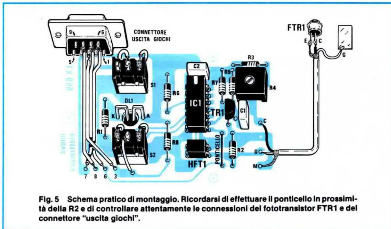
Fig. 5 Schema pratico di montaggio. Ricordarsi di effettuare il ponticello in prossimità della R2 e di controllare attentamente le connessioni del fototransistor FTR1 e del connettore "uscita giochi".
