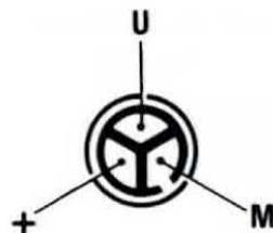
**Fig. 11** A volte il microfono presenta già uno spezzone di filo schermato, (schermo a Massa e filo centrale Uscita) più un secondo filo per il positivo di alimentazione.
