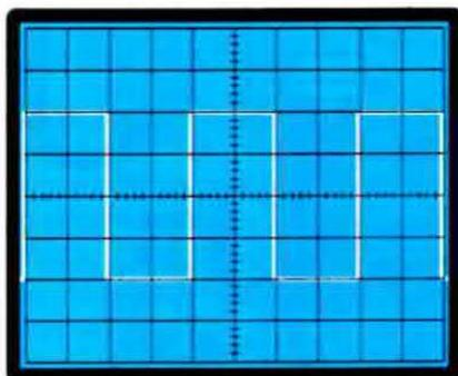
**Fig. 4** Pertanto se non vogliamo leggere una frequenza errata, cioè doppia o tripla, è assolutamente necessario applicare il condensatore C2 in uscita dell'oscillatore in modo da eliminare queste oscillazioni spurie.
