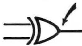
Fig. 2 Nei PLL, invece, viene utilizzato l'OR esclusivo, cioè lo stesso simbolo di fig. 1 sprovvisto del cerchietto in uscita.
