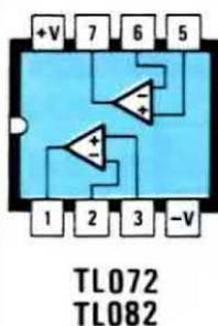
Fig. 26 Connessioni viste da sopra, dell'integrato TL.082. In questo circuito potrete montare anche degli LF.353 - TL.072 - uA.772.
