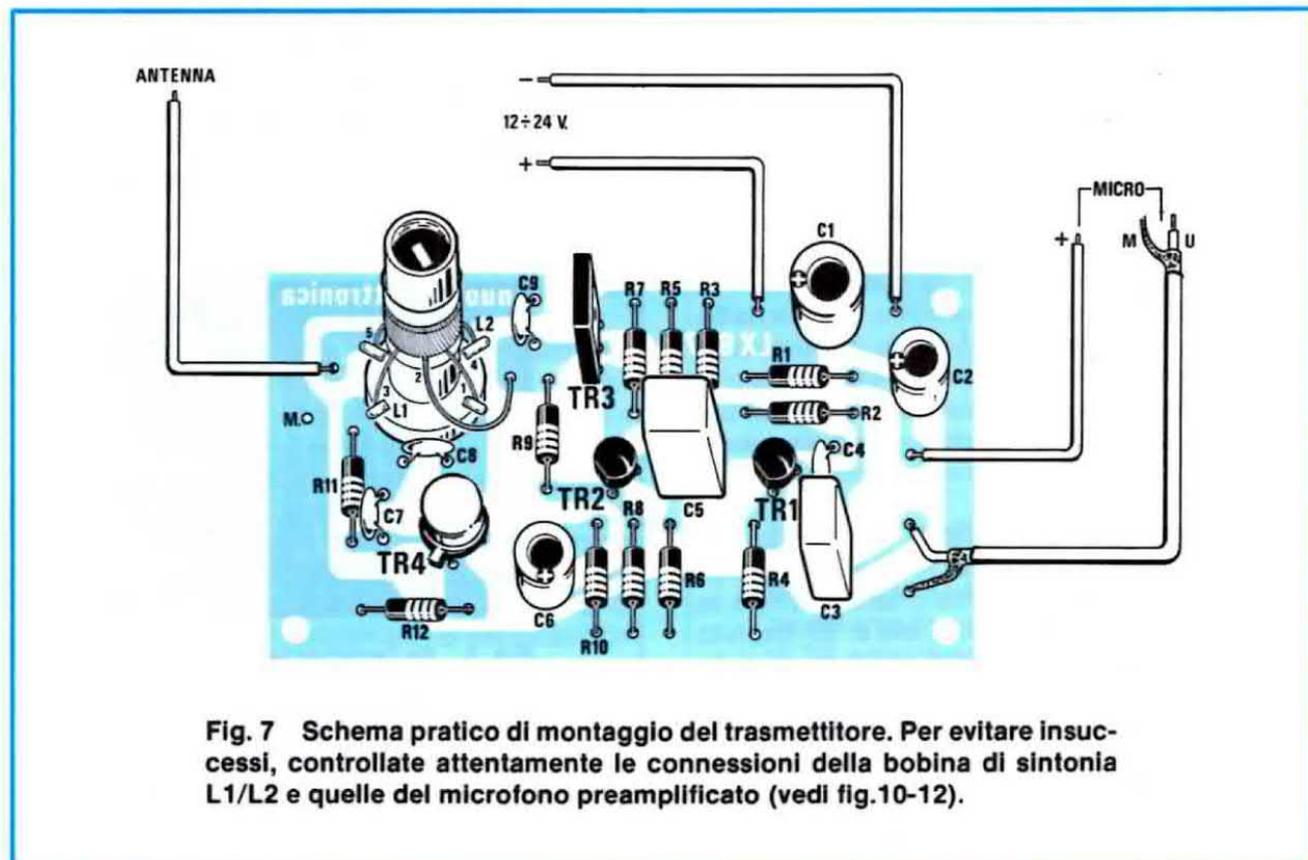
**Fig. 7** Schema pratico di montaggio del trasmettitore. Per evitare insuccessi, controllate attentamente le connessioni della bobina di sintonia L1/L2 e quelle del microfono preamplificato (vedi fig.10-12).
