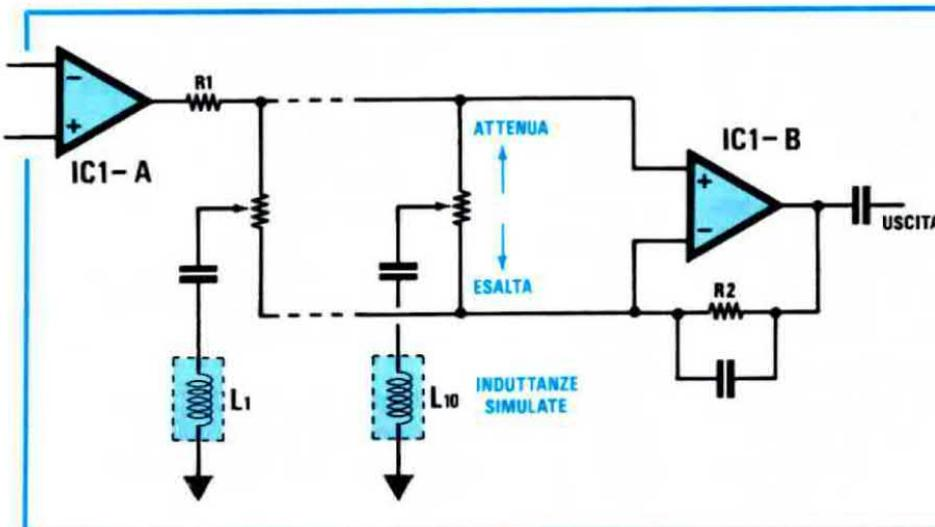
**Fig. 5** Applicando sui due ingressi di IC1/B un potenziometro e al cursore di questo, un'induttanza simulata, potrete attenuare od esaltare la frequenza di risonanza, spostando il cursore ai due estremi.
