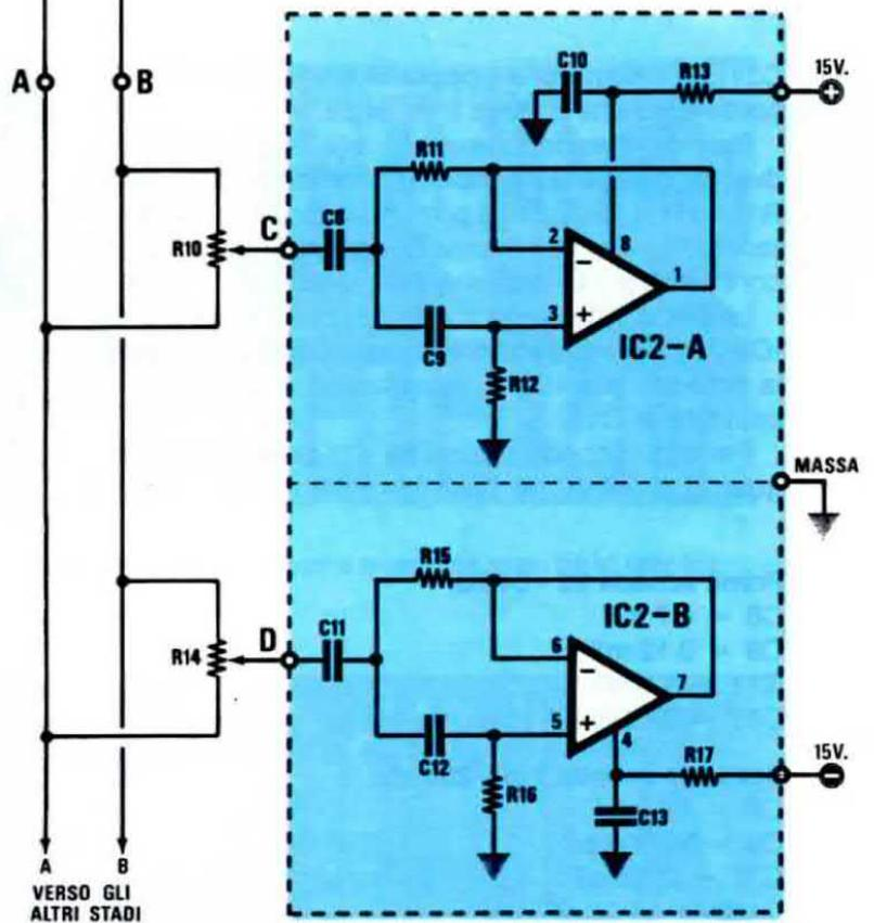
Fig. 6 In tale schema, abbiamo riportato il solo stadio preamplificatore/equalizzatore (vedi IC1/A e IC1/B) più un solo duplice filtro (riquadro in colore con IC2/A e IC2/B), in quanto gli altri quattro, esclusi i valori di C8-C9 e C11-C12, risultano equivalenti.
