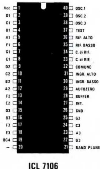
**Fig. 6** Connessioni del transistor BC.237 e dell'integrato 7106.
