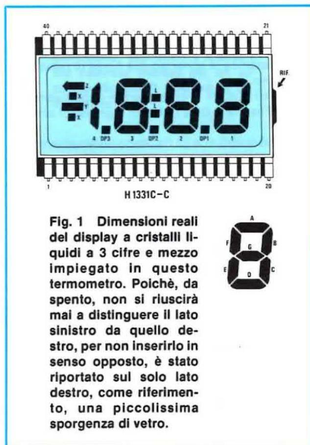
**Fig. 1** Dimensioni reali del display a cristalli liquidi a 3 cifre e mezzo impiegato in questo termometro. Poichè, da spento, non si riuscirà mai a distinguere il lato sinistro da quello destro, per non inserirlo in senso opposto, è stato riportato sul solo lato destro, come riferimento, una piccolissima sporgenza di vetro.
