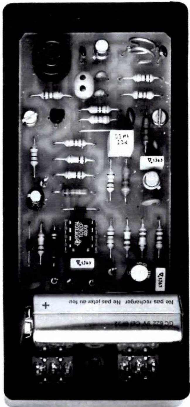
**Il mobiletto del ricevitore, di dimensioni maggiori rispetto a quello del trasmettitore, è già dotato di una griglia per la fuoriuscita del suono. Come vedesi in figura, in basso dovrete applicare i due deviatori S1 e S2 e nello spazio che rimane tra quest'ultimo e il circuito stampato, troverà posto la pila di alimentazione.**
