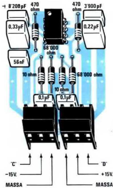
**Fig. 18** Schema pratico di montaggio del terzo doppio filtro, relativo alla frequenza di 500-1.000 Hz. Come per le schede precedenti, anche su questa dovreste collegare, in parallelo, più capacità per C9-C8 e C12-C11.
