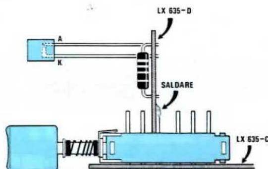
una volta inserito in ogni zoccolo l'integrato TL.082, rivolgendo correttamente il lato su cui è presente il "punto" di riferimento, ogni circuito sarà pronto per essere innestato nei connettori della piastra sulla quale avrete precedentemente montato i dieci potenziometri.
