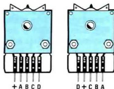
**Fig. 4** La disposizione dei terminali A-B-C-D su di un commutatore binario, potrete trovarla come riportato nella figura di sinistra oppure come in quella di destra.
