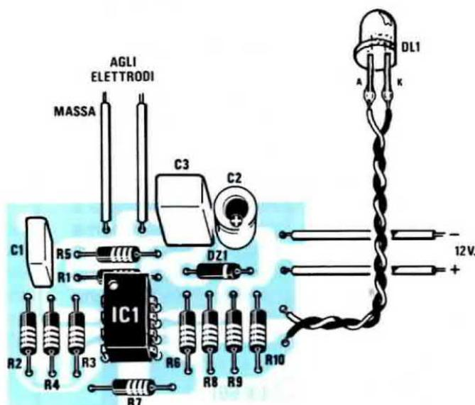
questo circuito può essere utilizzato anche per il radiatore di un'auto, quindi su un circuito di alimentazione la cui tensione può variare da un minimo di 10 volt ad un massimo di 15 e più volt, abbiamo applicato dopo la resistenza R8 un diodo zener da 15 volt per proteggere l'integrato da qualsiasi sovratensione.
