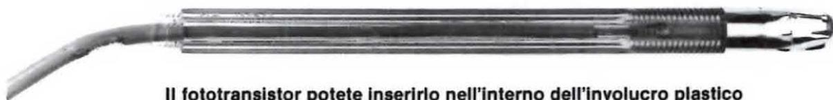
**Il fototransistor potete inserirlo nell'interno dell'involucro plastico di una penna a sfera o di un normale pennarello.**
