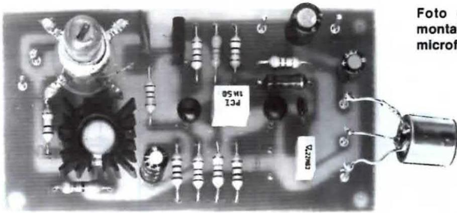
Foto del circuito già montato e completo di microfono.
