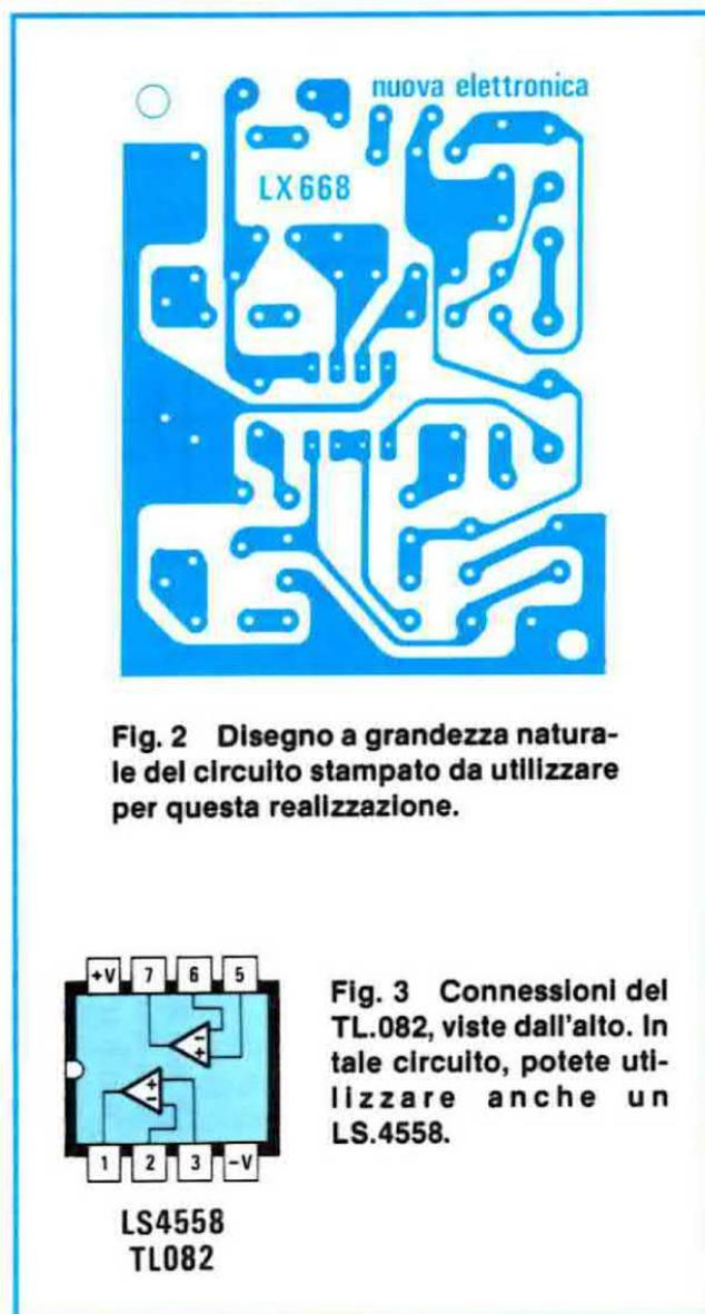
Fig. 2 Disegno a grandezza naturale del circuito stampato da utilizzare per questa realizzazione.
