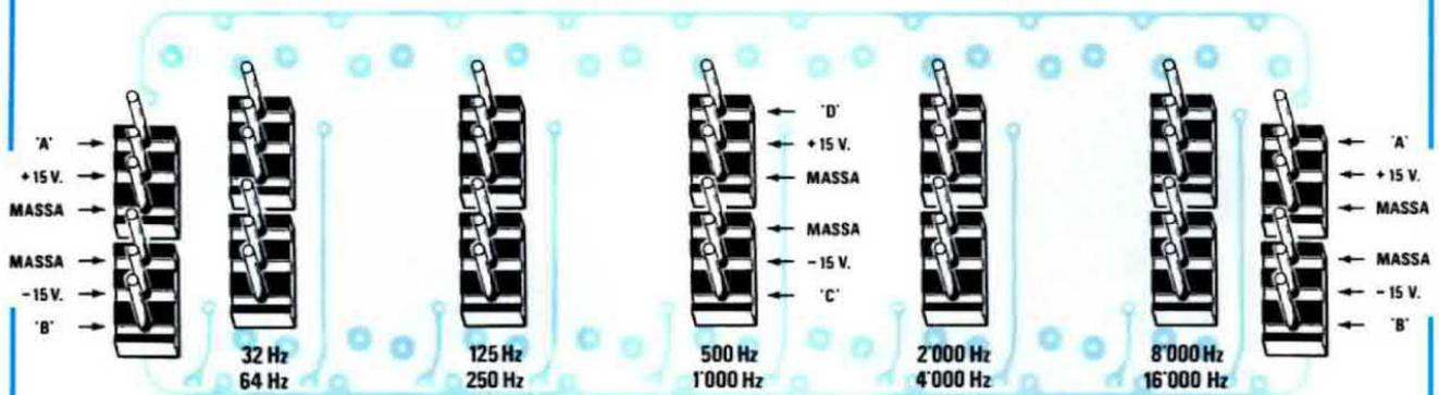
**Fig. 11** Come vedesi in questo disegno, sui due connettori esterni necessari a ricevere la scheda dello stadio preamplificatore/equalizzatore, abbiamo indicato i terminali che fanno capo agli ingressi A-B di IC1/B (vedi fig.6) e le due alimentazioni di 15 volt. Lo stesso dicasi per i connettori delle schede dei filtri.
