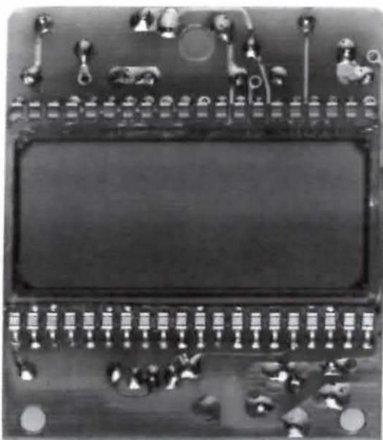
Intersil, cioè un completo voltmetro digitale già provvisto di decodifica per pilotare un display a cristalli liquidi a 3 cifre e mezzo.
