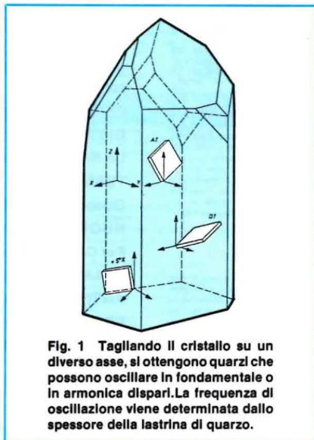
**Fig. 1** Tagliando il cristallo su un diverso asse, si ottengono quarzi che possono oscillare in fondamentale o in armonica dispari. La frequenza di oscillazione viene determinata dallo spessore della lastrina di quarzo.
