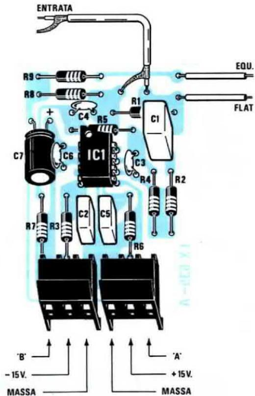
**Fig. 13** Schema pratico di montaggio della scheda LX.635/A. Ricordatevi di collocare il condensatore elettrolitico C7 in posizione orizzontale.
