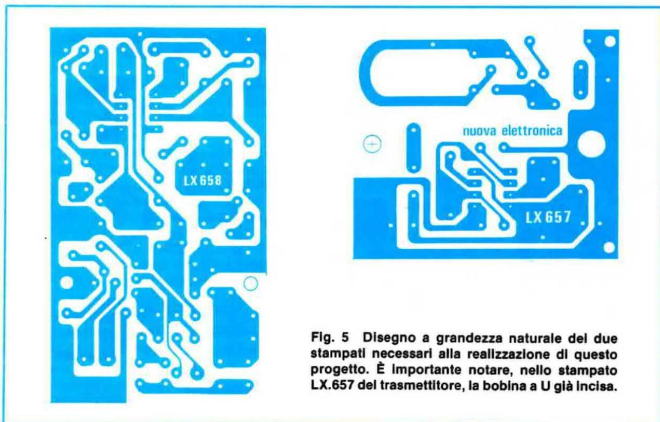
Fig. 5 Disegno a grandezza naturale dei due stampati necessari alla realizzazione di questo progetto. È importante notare, nello stampato LX.657 del trasmettitore, la bobina a U già incisa.
