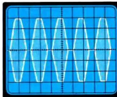
**Fig. 5** Se l'ampiezza del segnale di BF supera il livello massimo consentito, il segnale di AF risulterà "sovrarmodulato", cioè un'onda squadrata equivalente ad una elevata distorsione.
