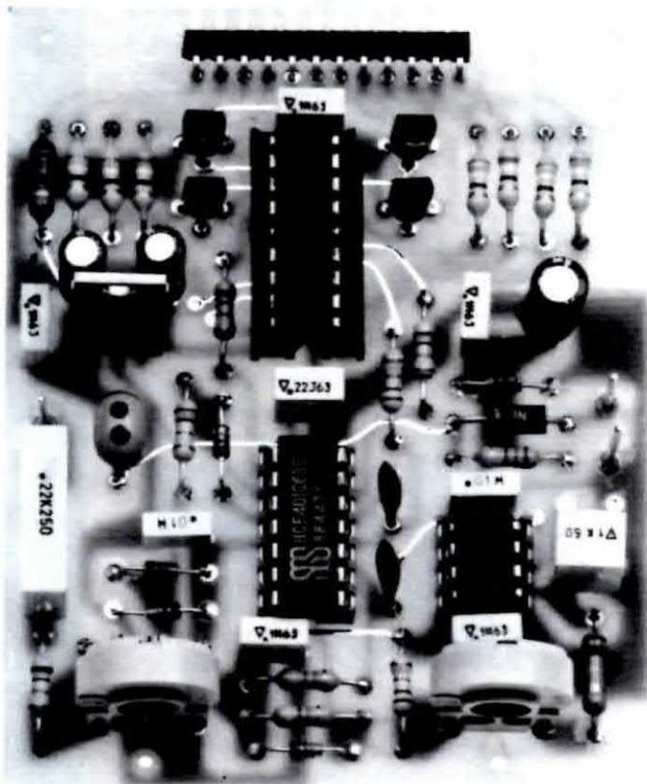
**A montaggio ultimato, dovrete inserire sullo stampato base LX.696 la scheda del display siglata LX.697 come visibile in questa foto. Vi ricordiamo che la scheda del display LX.697, utilizzata per questo contagiri, serve anche per il contagiri a PLL presentato a pag. 60. Prima di fornire tensione al circuito, controllate sempre che una goccia di stagno, caduta involontariamente, non abbia messo in corto due piste adiacenti.**
