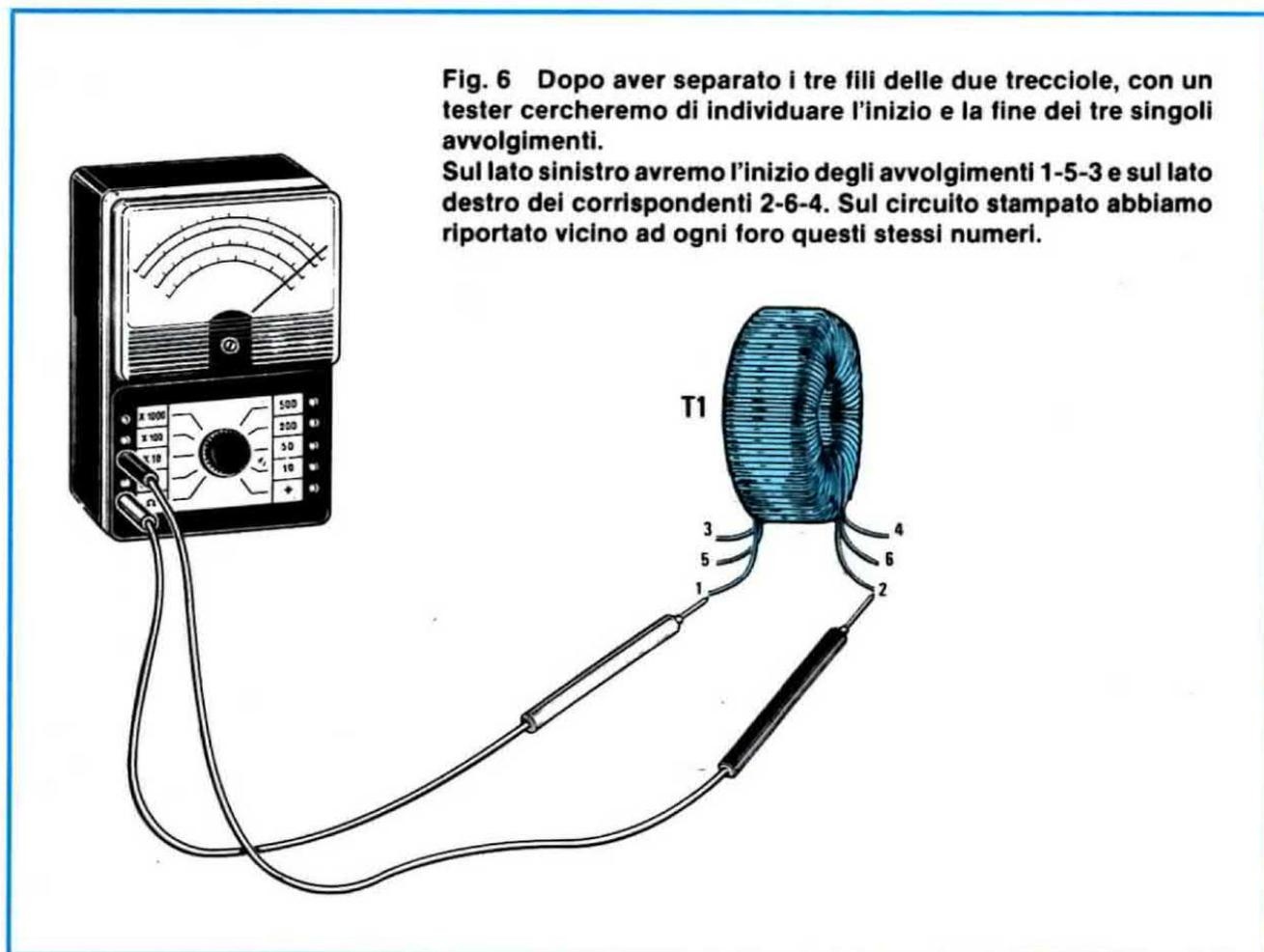
**Fig. 6** Dopo aver separato i tre fili delle due trecce, con un tester cercheremo di individuare l'inizio e la fine dei tre singoli avvolgimenti. Sul lato sinistro avremo l'inizio degli avvolgimenti 1-5-3 e sul lato destro dei corrispondenti 2-6-4. Sul circuito stampato abbiamo riportato vicino ad ogni foro questi stessi numeri.
