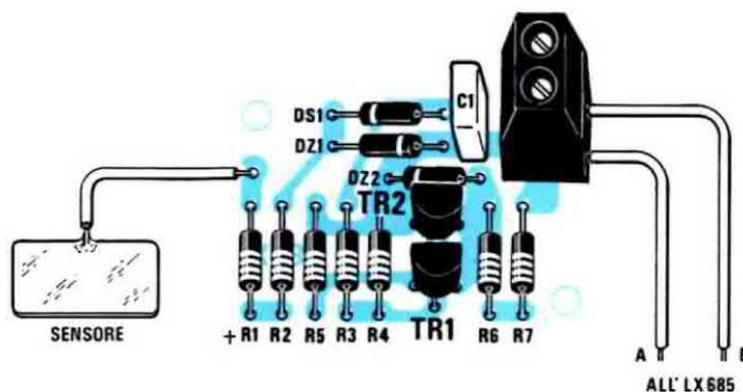
Fig. 8 Qui sopra lo schema pratico di montaggio dell'estensore siglato LX.686.
