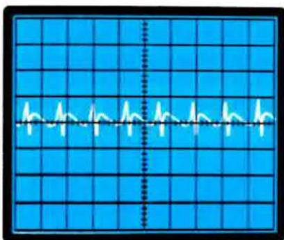
**Fig. 16** Se sullo schermo notate una forma d'onda con dei picchi molto accentuati, come vedesi in questa foto, significa che l'ampiezza applicata sull'ingresso è troppo elevata, quindi il segnale sinusoidale prelevato in uscita risulta tosato come potete osservare in fig. 3.
