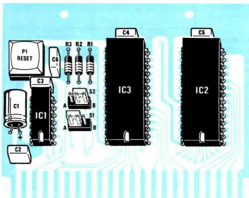
**Fig. 3** Schema pratico di montaggio. Si noti il condensatore C1 posto in posizione orizzontale e i due connettori S1-S2 per programmare l'indirizzo delle Ram.
