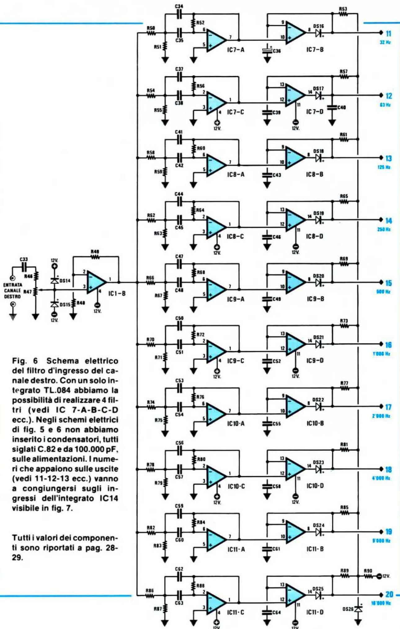
Fig. 6 Schema elettrico del filtro d'ingresso del canale destro. Con un solo integrato TL.084 abbiamo la possibilità di realizzare 4 filtri (vedi IC 7-A-B-C-D ecc.). Negli schemi elettrici di fig. 5 e 6 non abbiamo inserito i condensatori, tutti siglati C.82 e da 100.000 pF, sulle alimentazioni. I numeri che appaiono sulle uscite (vedi 11-12-13 ecc.) vanno a congiungersi sugli ingressi dell'integrato IC14 visibile in fig. 7.
