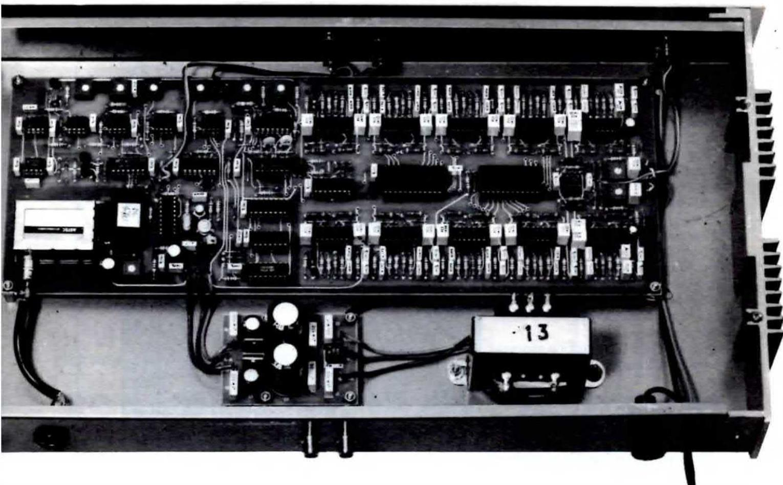
**Foto dell'analizzatore grafico - stereo di BF già montato entro il suo mobile, visto posteriormente. Sulla sinistra si può osservare il connettore di uscita del modulatore UHF dal quale preleveremo il segnale da applicare alla TV. Al centro sono visibili le due prese "Ingresso segnale BF" per i due canali e a destra il fusibile di rete. Si noti in basso la scheda dell'alimentatore duale LX.408 completo del trasformatore n. 13 utilizzato per fornire tensione a tale scheda.**
