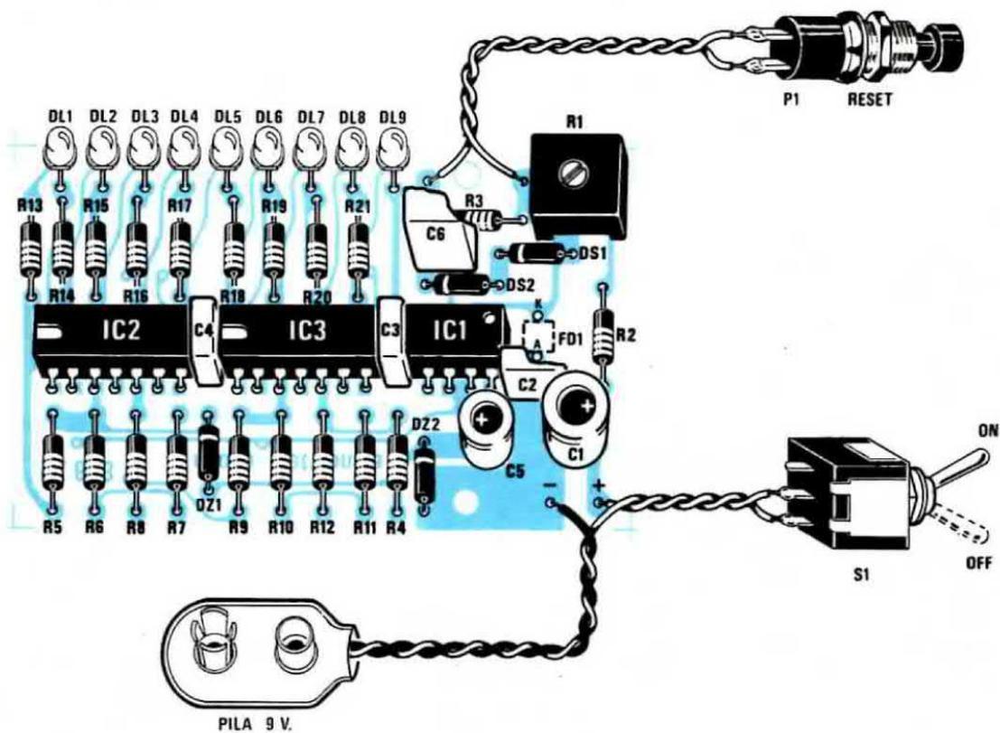
**Fig. 4** Schema pratico di montaggio dell'esposimetro. Poichè il circuito stampato è un doppia faccia a fori metallizzati, quindi non realizzabile artigianalmente, abbiamo ritenuto inutile riportarne il disegno. Si ricorda che bisognerà saldare il fotodiiodo FD1 dal lato opposto del circuito stampato (posizione vicino a IC1 e a R2).
