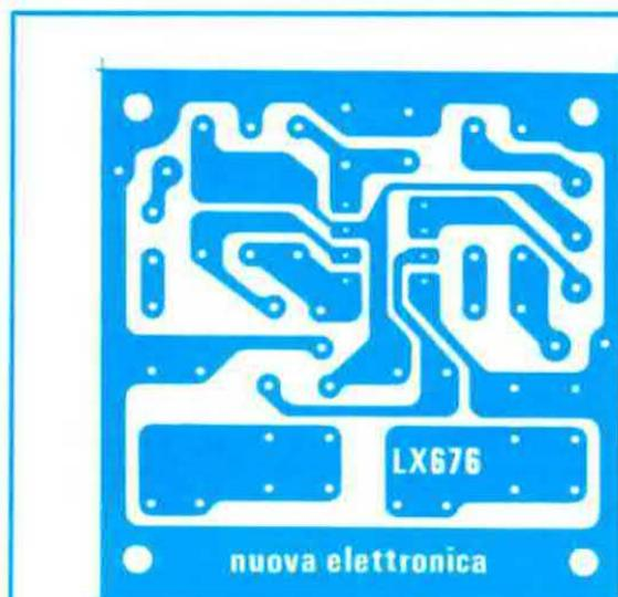
**Fig. 6** Disegno a grandezza naturale del circuito stampato siglato **LX.676**, necessario per la realizzazione di questo filtro, con il quale potrete misurare l'entità della distorsione su qualsiasi amplificatore o preamplificatore di BF.
