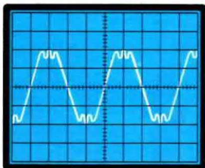
**Fig. 1** Se un amplificatore non è perfetto, in uscita, oltre alla frequenza fondamentale, possiamo trovare sovrapposte anche una infinità di frequenze armoniche che, riprodotte dall'altoparlante, modificheranno, il "suono" originale. In questa figura, abbiamo accentuato sulla frequenza fondamentale questo tipo di distorsione.
