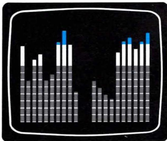
**Fig. 1** Costruendo questo analizzatore grafico di BF, potrete far apparire sullo schermo del vostro televisore 10 barre per il canale destro e 10 per il canale sinistro, ognuna centrata su una diversa frequenza. Ogni barra verticale appare in tre colori, Giallo-Blu-Rosso, che potrete modificare in Blu-Giallo-Rosso agendo su di un apposito deviatore.
