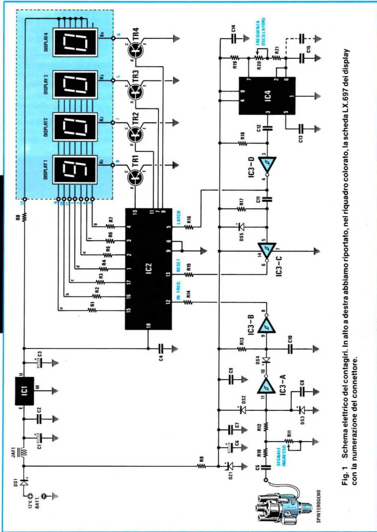
Fig. 1 Schema elettrico dei contagiri. In alto a destra abbiamo riportato, nel riquadro colorato, la scheda LX.697 del display con la numerazione del connettore.
