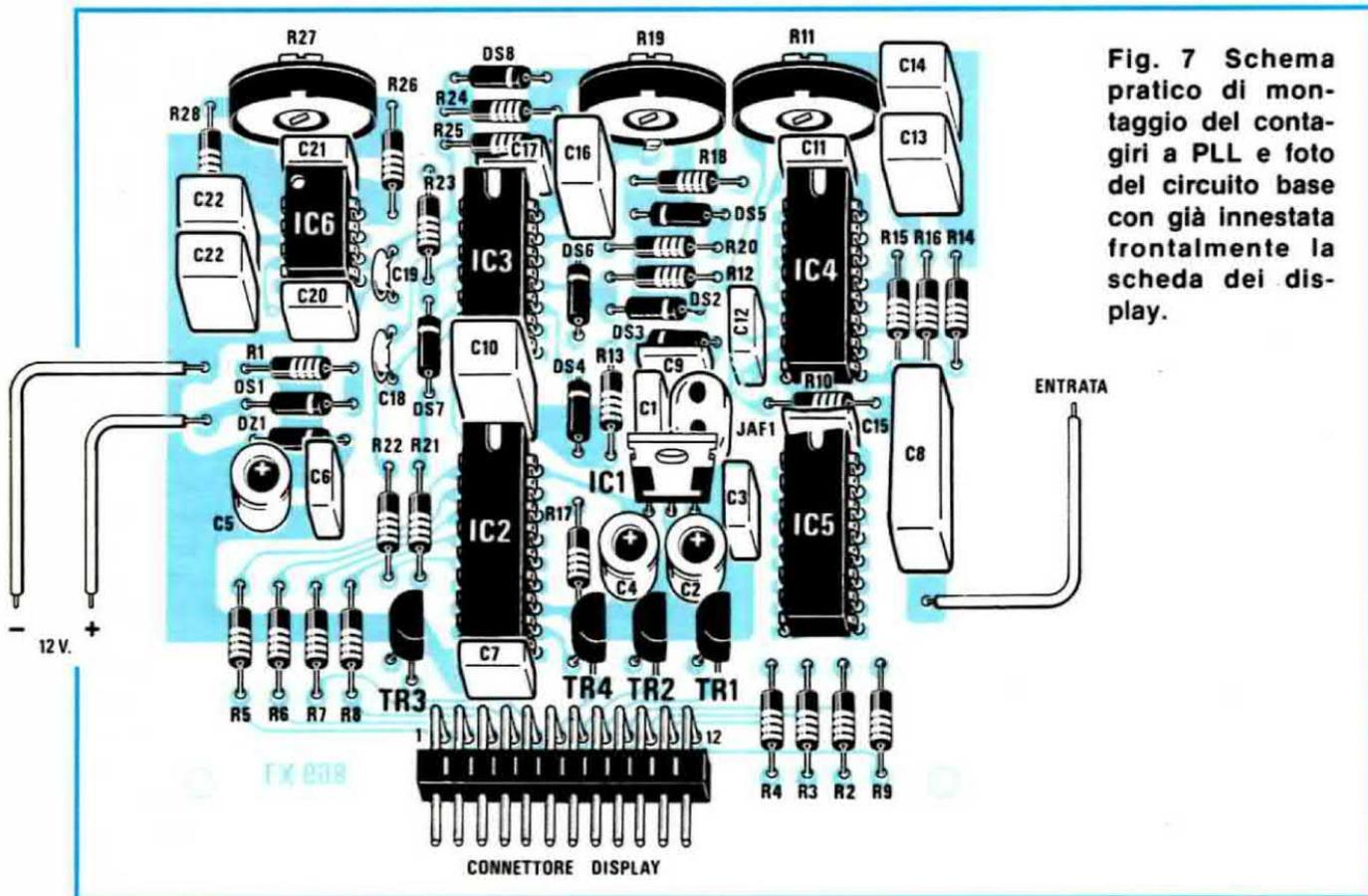
Fig. 7 Schema pratico di montaggio del contagiri a PLL e foto del circuito base con già innestata frontalmente la scheda dei display.
