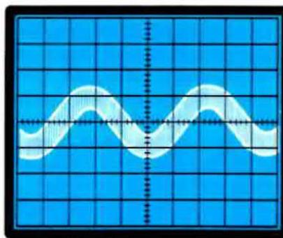
**Fig. 17** Se portando la sensibilità dell'oscilloscopio sui 10 - 20 mV/divisione, il segnale si presenta come in questa foto, significa che la calza di un cavetto schermato non risulta collegata a massa e quindi il preamplificatore o il distorsimetro capta del ronzio di alternata a 50 Hz.
