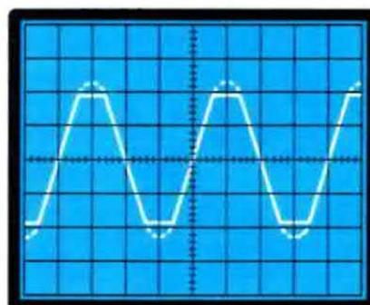
**Fig. 3** Se l'onda anziché essere spezzata al centro risulta "tosta" sulle due estremità, avremo una distorsione per saturazione. Questo tipo di distorsione si presenta quando l'ampiezza del segnale che applichiamo sull'ingresso di un qualsiasi preamplificatore o finale di BF, risulta superiore ai livelli massimi consentiti.
