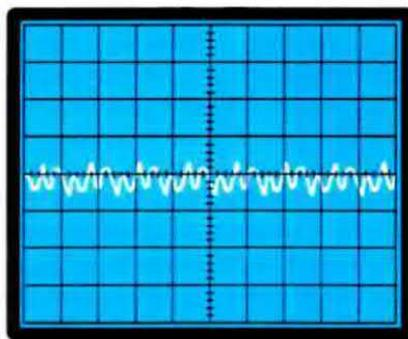
**Fig. 15** La forma d'onda che vedete qui sopra riportata è la più comune, perchè ciò che appare sono tutte le frequenze armoniche che risultano presenti sulla fondamentale. Minore risulterà la percentuale di queste armoniche, maggiore sarà la fedeltà di riproduzione.
