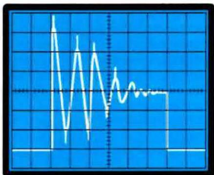
**Fig. 2** Dalle puntine dello spinterogeno esce un segnale che non può essere applicato direttamente sull'ingresso di un contatore digitale, perchè troppo "sporco". Se non si eliminassero tutte le autoscillazioni spurie dovute ai rimbalzi sul contatto delle puntine, il nostro contagiri rilevrebbe una frequenza maggiore di quella reale, indicando così un numero di giri ben superiore a quello a cui ruota il motore.
