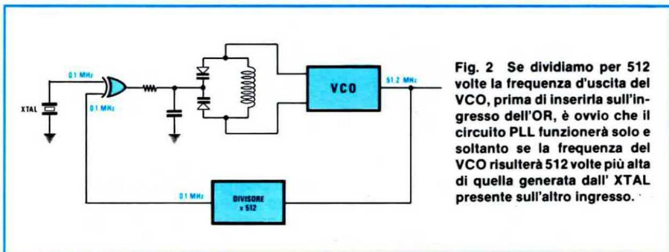
Fig. 2 Se dividiamo per 512 volte la frequenza d'uscita del VCO, prima di inserirla sull'ingresso dell'OR, è ovvio che il circuito PLL funzionerà solo e soltanto se la frequenza del VCO risulterà 512 volte più alta di quella generata dall' XTAL presente sull'altro ingresso.
