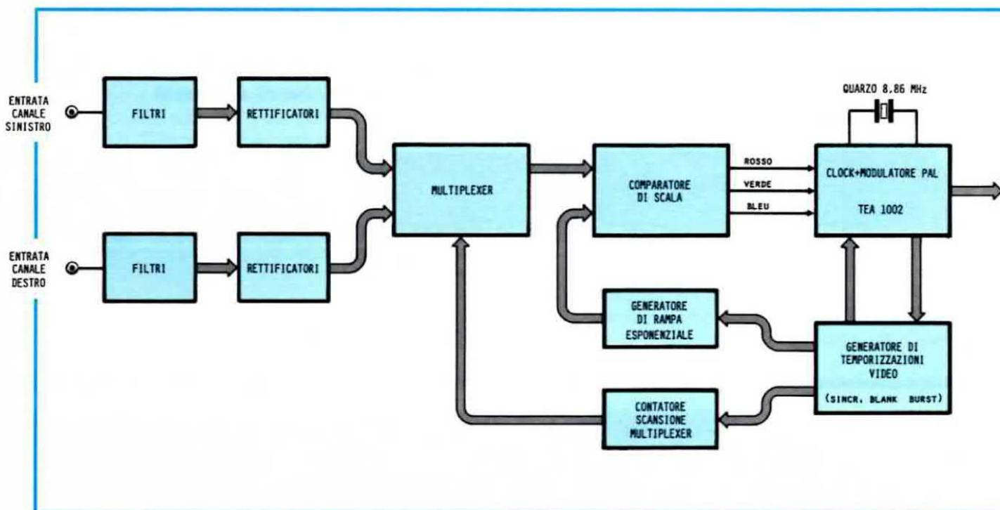
ingresso con la tensione proveniente dal blocco **generatore di rampa esponenziale**, stabilisce l'altezza ed il colore da assegnare, in quell'istante, alla colonna visualizzata.
