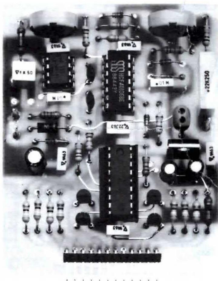
Foto della piastra base di questo contagiri. Si noti in basso il connettore per innestare il circuito stampato dei display visibile a pag. 57.
