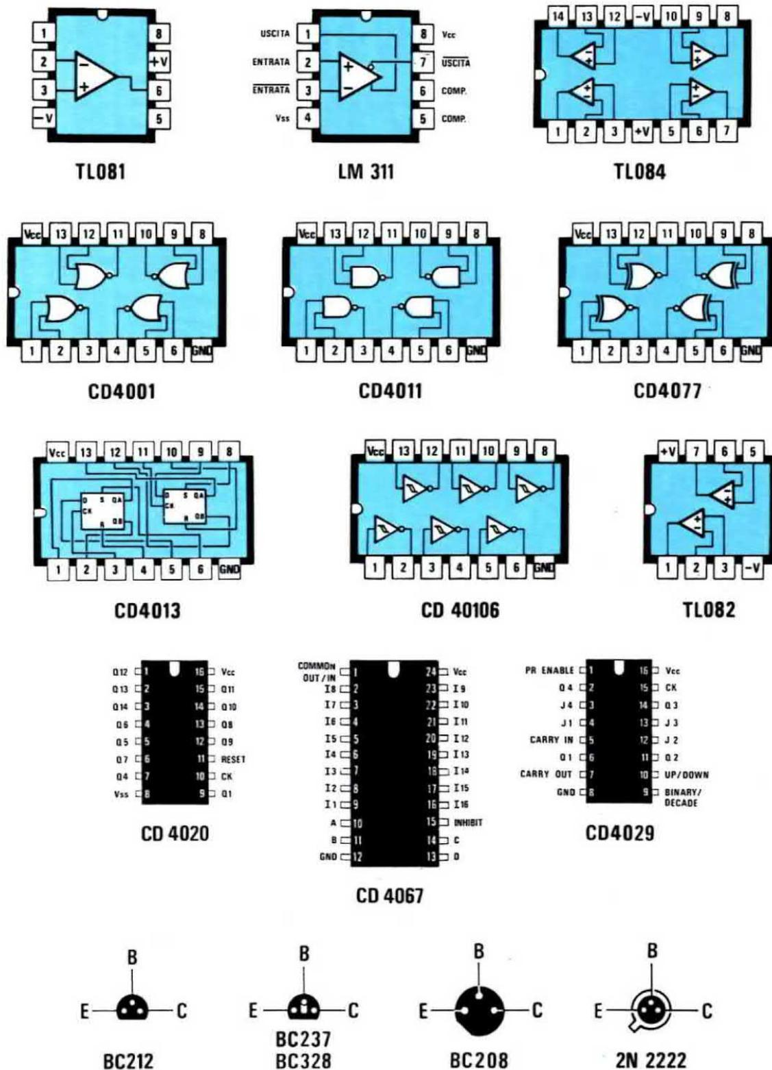
Fig. 8 Connessioni degli integrati utilizzati in questo progetto viste dall'alto e di tutti i transistor visti invece dal basso, cioè dal lato in cui i terminali fuoriescono dal corpo.
