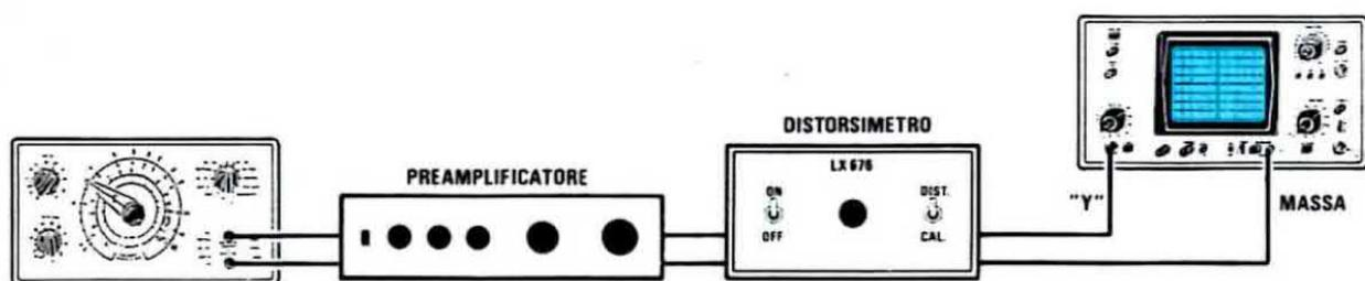
**Fig. 9** Volendo controllare la distorsione di un preamplificatore HI-FI, inseriremo il distorsimetro tra l'uscita del preamplificatore e l'ingresso dell'oscilloscopio, poi regoleremo l'ampiezza del segnale in ingresso in modo da non saturare, come visibile in fig. 3, la forma dell'onda sinusoidale.
