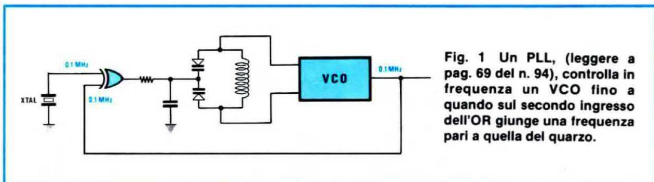
Fig. 1 Un PLL, (leggere a pag. 69 del n. 94), controlla in frequenza un VCO fino a quando sul secondo ingresso dell'OR giunge una frequenza pari a quella del quarzo.
