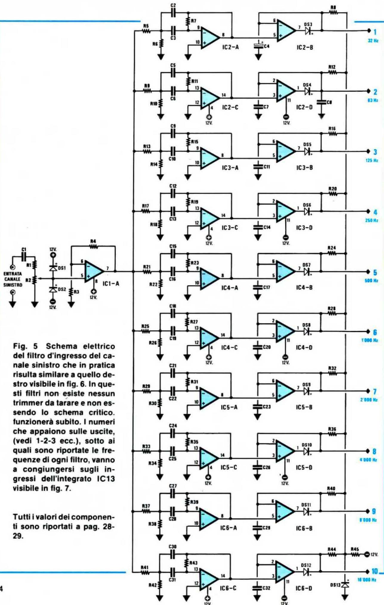
**Fig. 5** Schema elettrico del filtro d'ingresso del canale sinistro che in pratica risulta simile a quello destro visibile in fig. 6. In questi filtri non esiste nessun trimmer da tarare e non essendo lo schema critico, funzionerà subito. I numeri che appaiono sulle uscite, (vedi 1-2-3 ecc.), sotto ai quali sono riportate le frequenze di ogni filtro, vanno a congiungersi sugli ingressi dell'integrato IC13 visibile in fig. 7.
