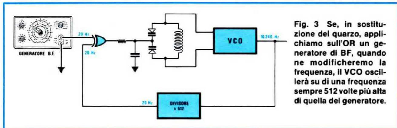
Fig. 3 Se, in sostituzione del quarzo, applichiamo sull'OR un generatore di BF, quando ne modificheremo la frequenza, il VCO oscillerà su di una frequenza sempre 512 volte più alta di quella del generatore.
