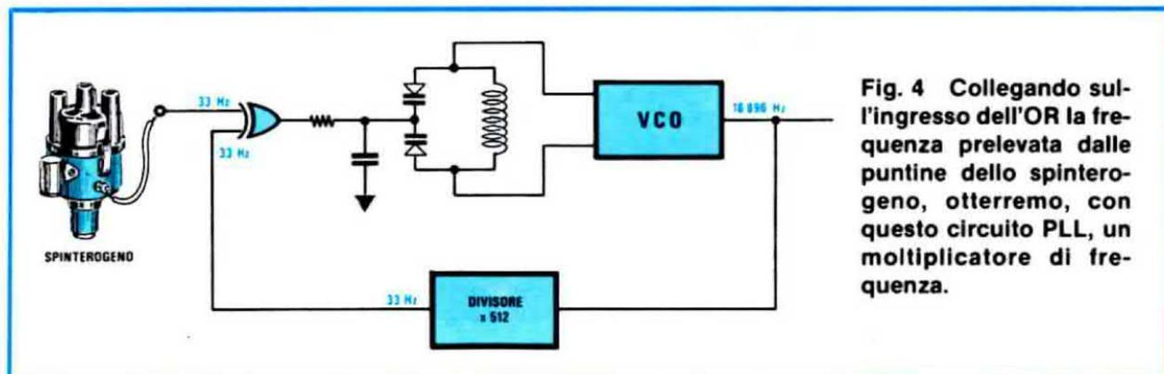
Fig. 4 Collegando sull'ingresso dell'OR la frequenza prelevata dalle puntine dello spinterogeno, otterremo, con questo circuito PLL, un moltiplicatore di frequenza.
