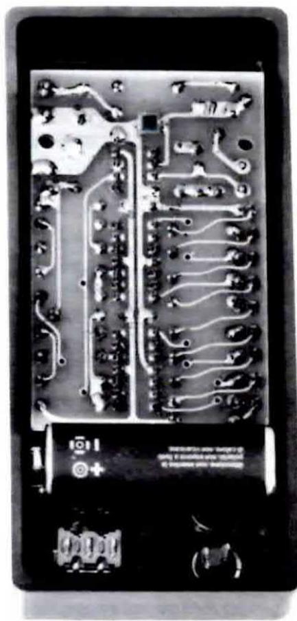
In questa foto è visibile sulla parte superiore del circuito stampato il fotodiode che verrà così a trovarsi di fronte alla finestra del coperchio visibile qui di lato. Si noti la posizione in cui dovremo collegare la pila e i due comandi S1 e P1.
