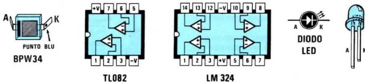
Fig. 7 Connessioni degli integrati visti dall'alto e quelli del fotodiode e diodi led. Per individuare nel fotodiode i terminali A e K guardatelo internamente: il terminale A fa capo ad un sottile terminale, che non troviamo invece dal lato opposto K. Per i diodi led, il terminale A è sempre più lungo del terminale K.
