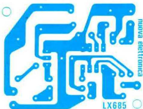
Fig. 2 Disegno a grandezza naturale del circuito stampato siglato LX.685, da utilizzare per il montaggio di questo magico ed interessante sensore.
