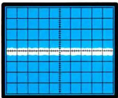
**Fig. 14** Se, regolando la frequenza del generatore di BF, il minimo segnale che riuscite ad ottenere è una riga molto piena, come visibile in figura, significa che sul vostro apparato sono presenti una infinità di armoniche, oppure che quest'ultimo risulta molto rumoroso.
