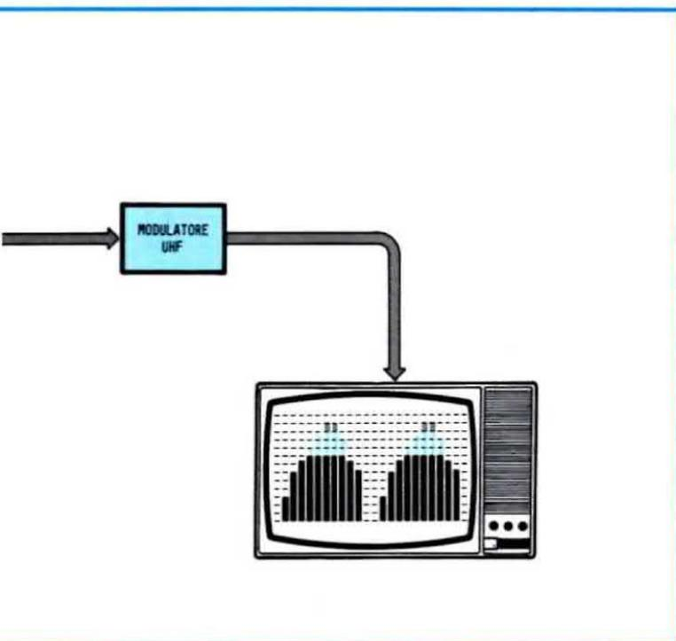
Fig. 3 Con questo schema a blocchi risulterà più facile comprendere le varie funzioni svolte da questo analizzatore. Per poter trasferire l'immagine su di un normale TV, il segnale video che preleveremo dall'uscita dell'integrato TEA.1002, lo utilizzeremo per modulare un minitrasmettore in gamma UHF.
