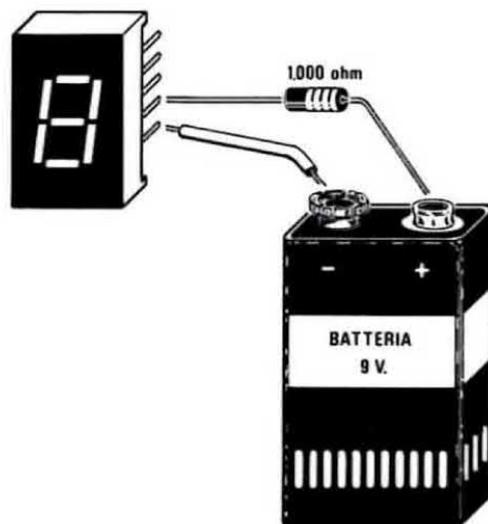
ora il terminale negativo della pila sul primo piedino posto in basso a destra ed il positivo con la resistenza posta in serie, sul secondo piedino.
