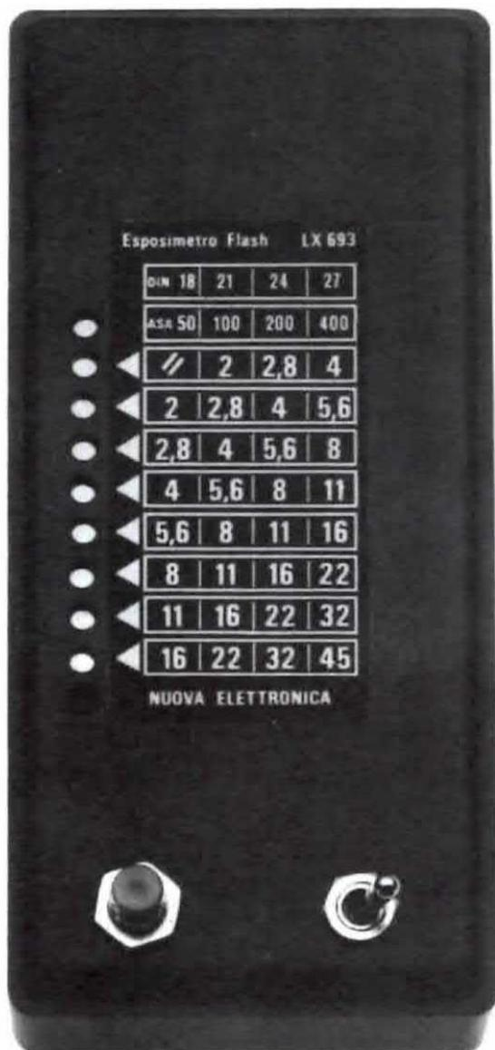
Assieme al mobiletto dell'esposimetro vi forniremo una etichetta autoadesiva con sopra riportati i diaframmi da utilizzare in funzione alla sensibilità della pellicola impiegata. L'ultimo diodo led posto nella colonna in alto è quello di reset.
