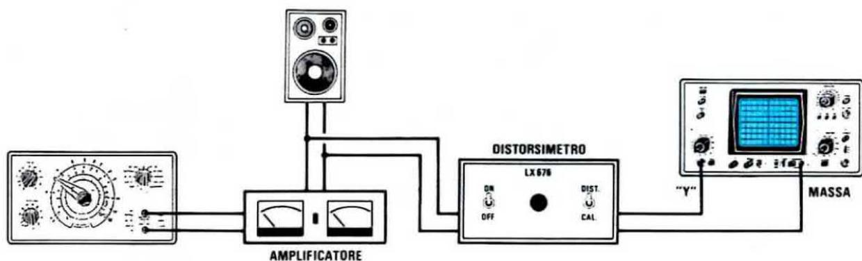
**Fig. 10** Volendo invece controllare la distorsione di uno stadio finale di potenza, potremo prelevare il segnale direttamente sui due fili d'uscita per la cassa acustica. Ricordatevi che la distorsione di uno stadio finale normalmente viene controllata ad una potenza di poco superiore al 50% di quella massima.
