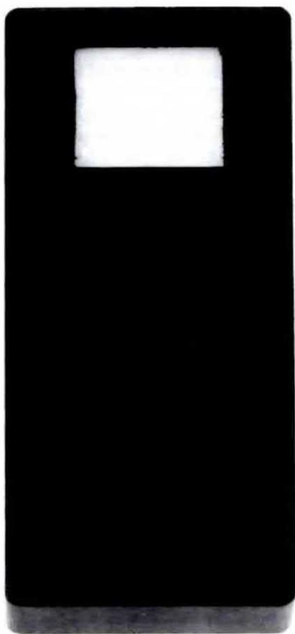
Dovremo asportare la grata quadrata, stampata su un solo coperchio, utilizzando la punta del saldatore e incollare all'interno del foro ottenuto, il pezzetto di plastica color bianco latte che ci servirà da diffusore di luce.
