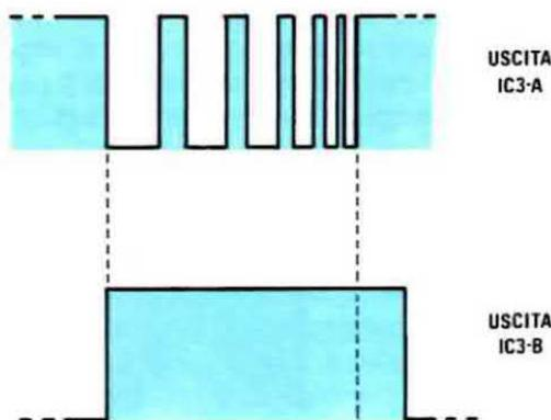
**Fig. 3** Per evitare questo inconveniente, comune a molti contagi, dovremo prima tosare il segnale su di un valore massimo di 9,7 volt, poi, risultando ancora presenti sull'uscita di IC3/A tutti i picchi positivi delle autoscillazioni spurie delle puntine, dovremo eliminarli utilizzando semplicemente un diodo, un condensatore e una resistenza, (vedi DS4 - C10-R13), più un secondo inverter siglato IC3/B.
