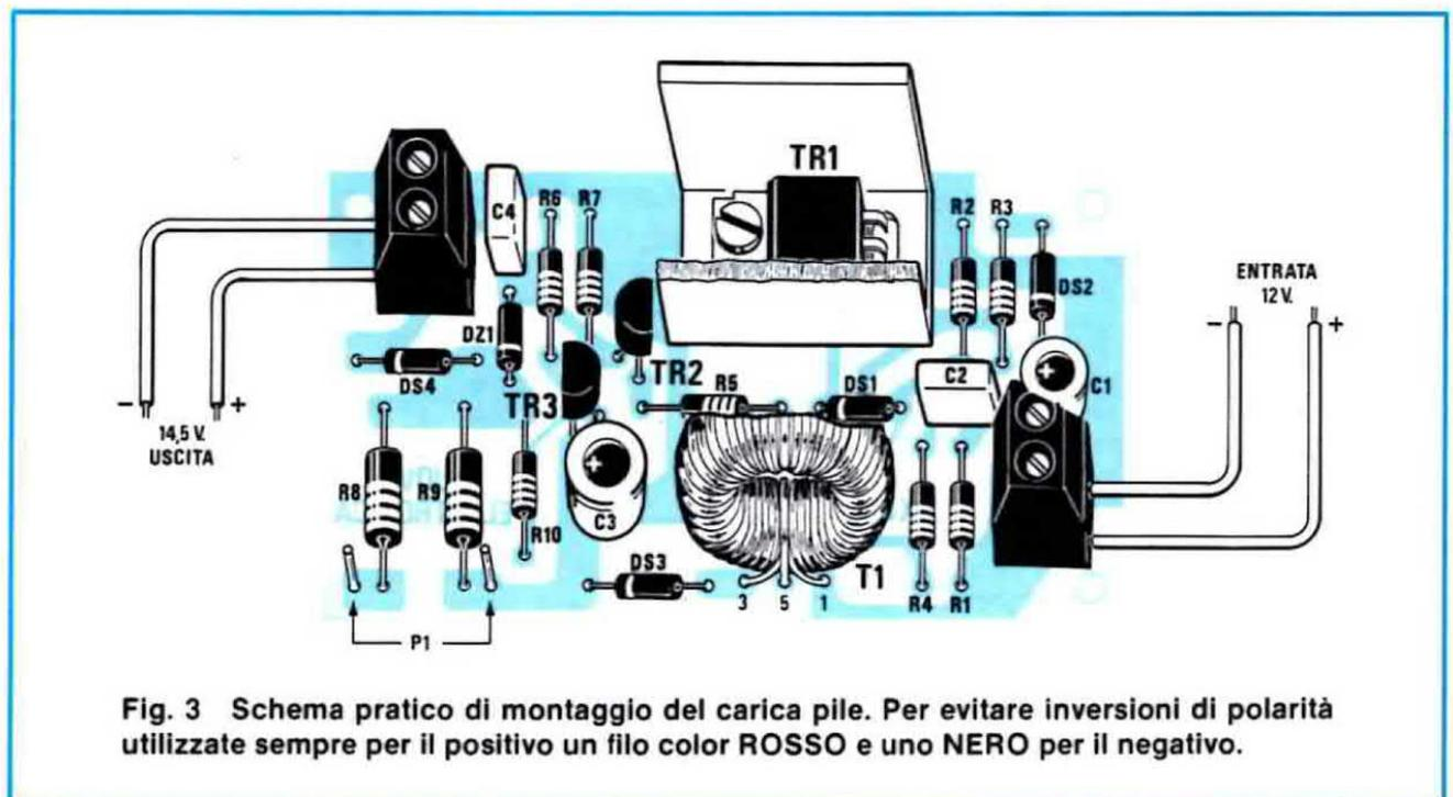
Fig. 3 Schema pratico di montaggio del carica pile. Per evitare inversioni di polarità utilizzate sempre per il positivo un filo color ROSSO e uno NERO per il negativo.
