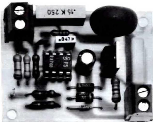
Foto del sensore per luci leggermente ingrandita. La morsettiera di sinistra ci servirà per eventuali estensioni, mentre quella di destra per collegare lampada e tensione di rete. Si noti, sopra al triac, l'impedenza antidisturbo JAF1.
