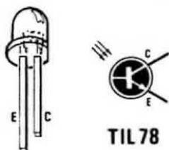
Fig. 2 In sostituzione del fototransistor TIL.64, noi ora inseriamo nel kit il fototransistor TIL.78 perchè, essendo di dimensioni ridotte, riesce più facile inserirlo all'interno di una biro. Come vedesi nella fig. 1 il terminale più corto C andrà collegato al filo che parte dal punto C presente sul circuito stampato, il terminale più lungo E andrà collegato alla calza metallica.
