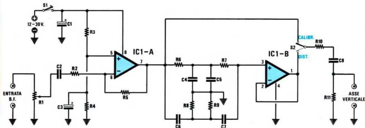
**Fig. 4** Schema elettrico del filtro che vi permetterà, utilizzando un oscilloscopio, di misurare la percentuale di distorsione.
