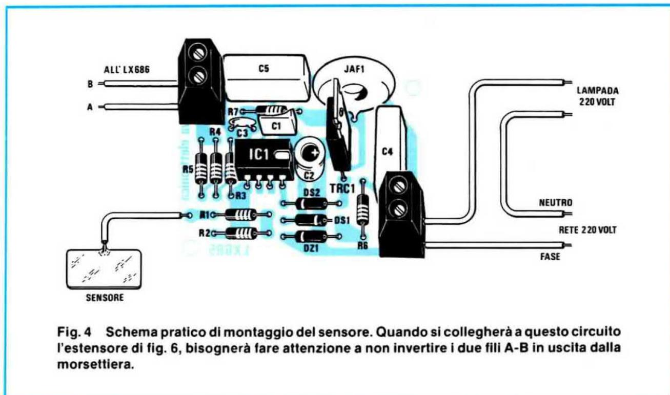
**Fig. 4** Schema pratico di montaggio del sensore. Quando si collegherà a questo circuito l'estensore di fig. 6, bisognerà fare attenzione a non invertire i due fili A-B in uscita dalla morsetteria.
