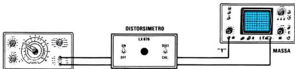
**Fig. 8** Per misurare la distorsione di un qualsiasi apparato HI-FI, oltre all'oscilloscopio è necessario possedere un generatore di BF. Come abbiamo spiegato nell'articolo, la prima operazione da compiere sarà quella di controllare la distorsione del segnale fornito in uscita dal nostro generatore BF.
