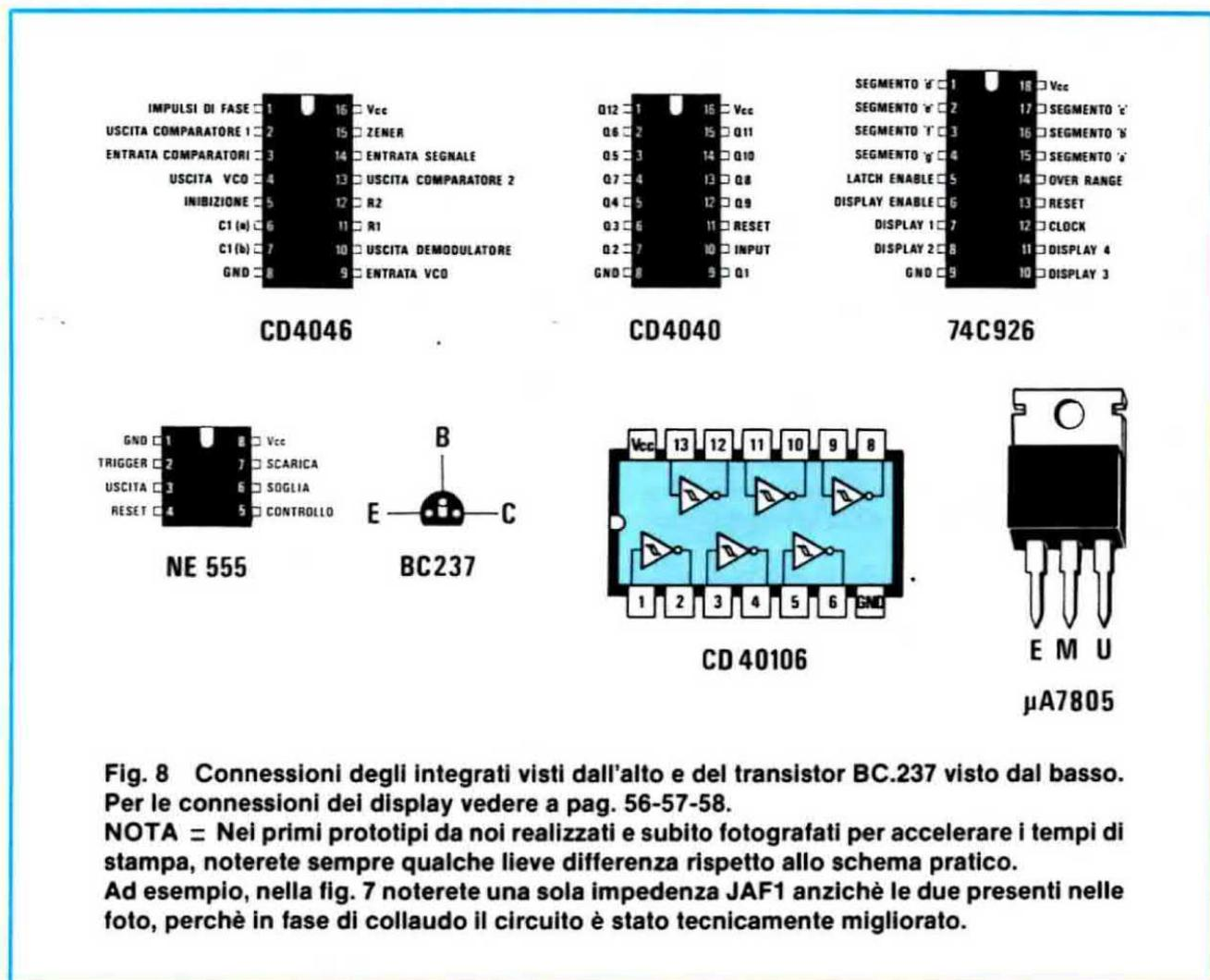
**Fig. 8** Connessioni degli integrati visti dall'alto e del transistor BC.237 visto dal basso. Per le connessioni dei display vedere a pag. 56-57-58.
