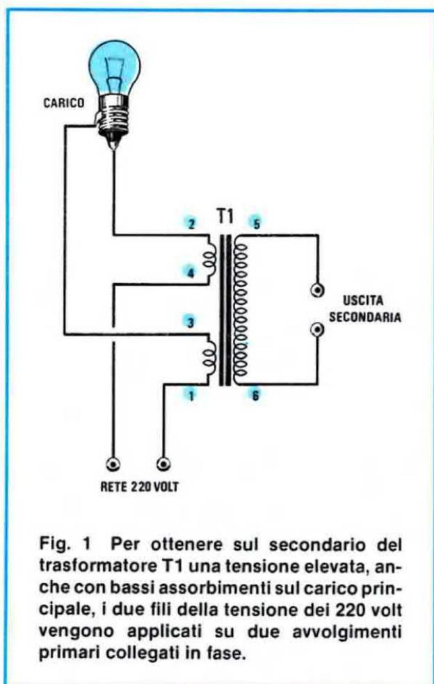
**Fig. 1** Per ottenere sul secondario del trasformatore T1 una tensione elevata, anche con bassi assorbimenti sul carico principale, i due fili della tensione dei 220 volt vengono applicati su due avvolgimenti primari collegati in fase.
