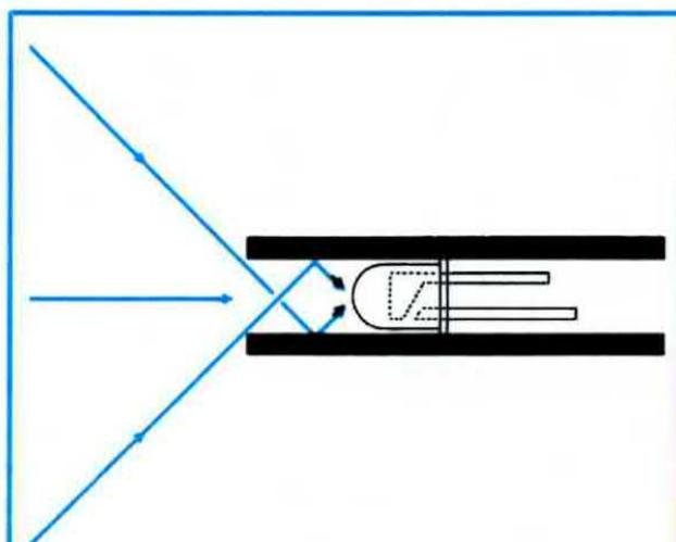
**Fig. 9** Se l'interno dell'involucro plastico in cui inserirete il fotodiode è lucido, cercate di renderlo opaco per evitare che della luce riflessa lateralmente lo raggiunga. Come spiegato nell'articolo, il fotodiode dovrà essere inserito all'interno dell'involucro ad una adeguata distanza.
