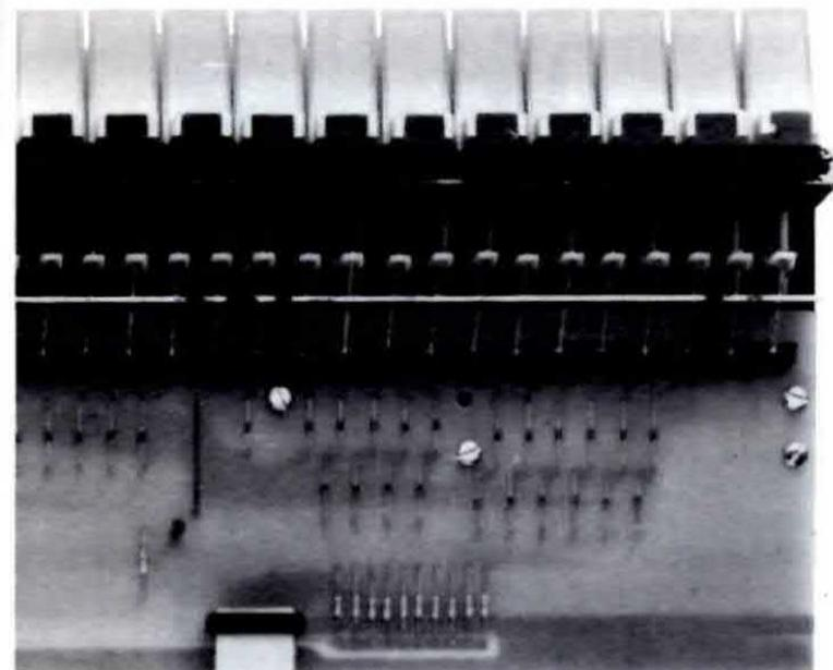
Foto del circuito stampato LX.690 già completo di tutti i suoi componenti e già fissato sotto la tastiera. Sotto ogni vite di fissaggio di tale circuito stampato dovrete inserire gli speciali distanziatori plastici che troverete nel kit.
