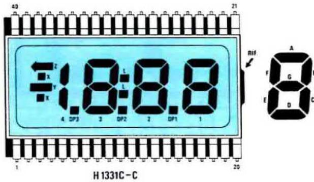
Fig. 5 Connessioni del display LCD. Si noti sulla destra la piccola sporgenza indicata con RIF. Questa sporgenza, come vedesi in fig. 7, andrà rivolta verso l'integrato IC1, diversamente il display non si accenderà.
