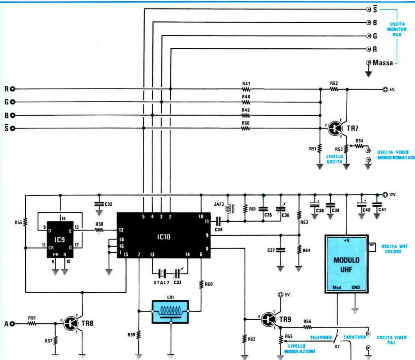
**Fig. 2** Schema elettrico del codificatore PAL, completo del microtrasmettitore UHF. Le lettere R-G-B-S e A riportate a sinistra e la C riportata in basso a destra, sono collegate con le corrispondenti visibili a destra in fig. 1.
