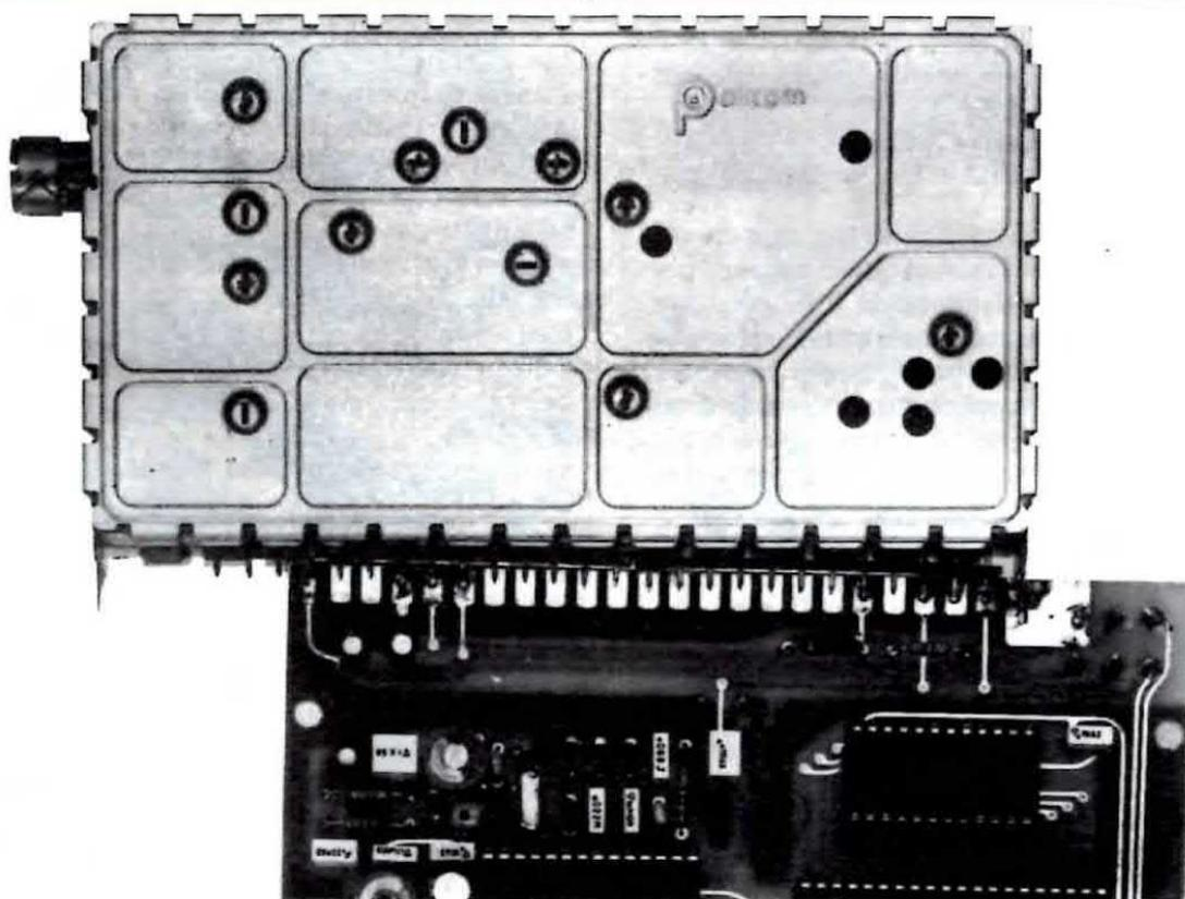
**Fig. 8** Come vedesi in questa foto, tutti i terminali (esclusi i primi tre posti sulla sinistra) del gruppo sintonizzatore VHF-UHF andranno saldati sulle piste presenti nel circuito stampato. Vi ricordiamo di inserire nella fessura del circuito stampato la linguella metallica di massa (posta a destra) che, poi, salderete sia sopra che sotto.
