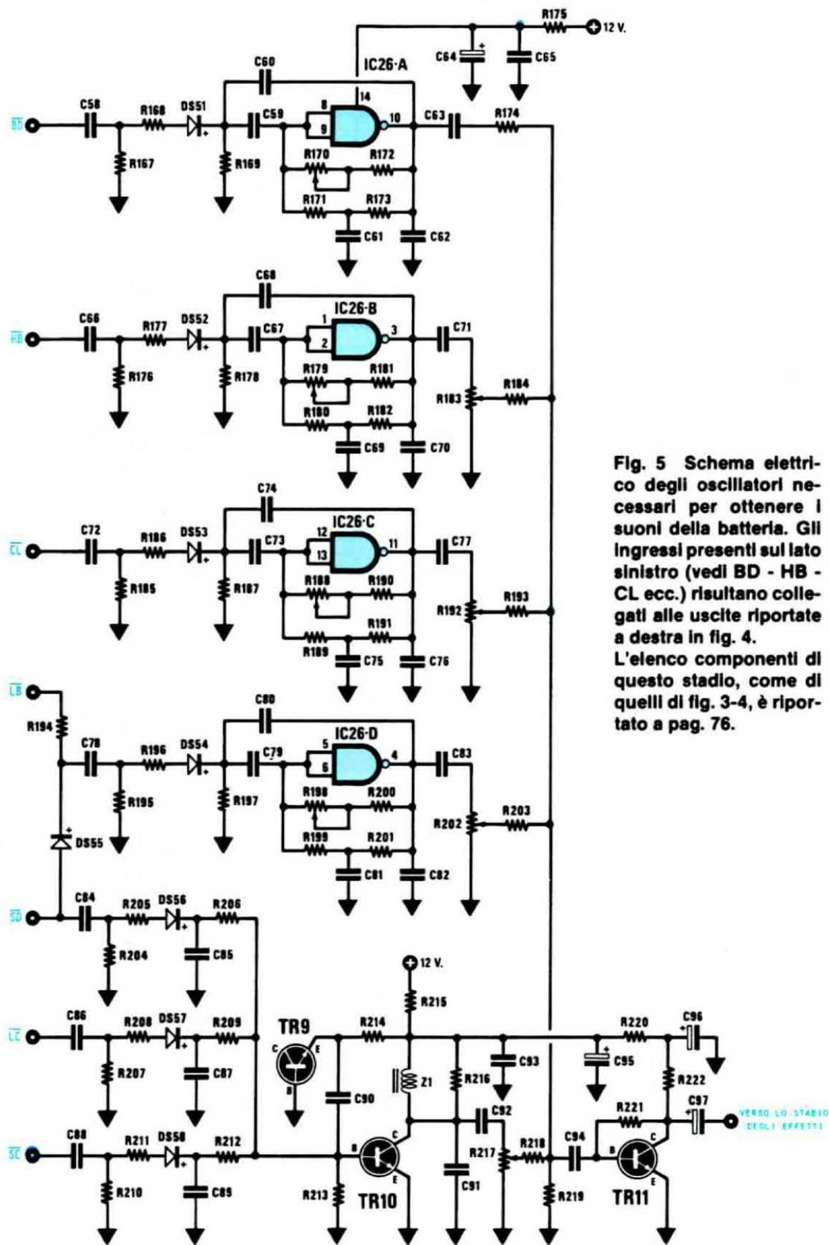
Fig. 5 Schema elettrico degli oscillatori necessari per ottenere i suoni della batteria. Gli ingressi presenti sul lato sinistro (vedi BD - HB - CL ecc.) risultano collegati alle uscite riportate a destra in fig. 4. L'elenco componenti di questo stadio, come di quelli di fig. 3-4, è riportato a pag. 76.
