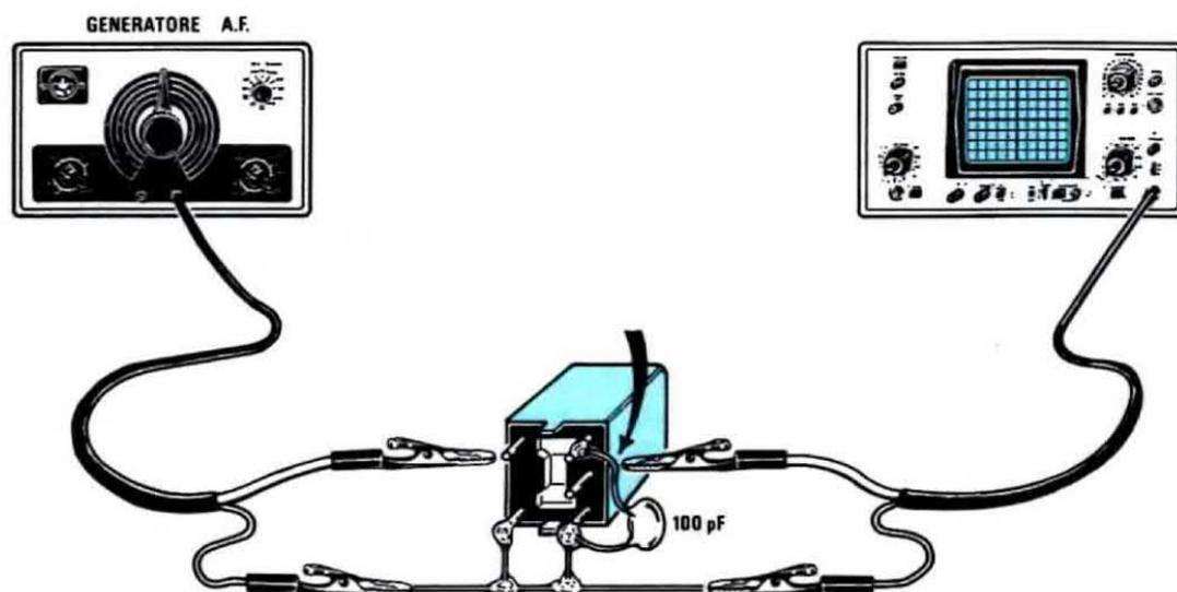
Fig. 10 Si può effettuare una misura più attendibile collegando il generatore di AF sull'avvolgimento secondario e l'oscilloscopio sugli estremi del primario. Se nella MF esiste già il condensatore di accordo, non è necessario collegare in parallelo al primario il condensatore da 100 pF, visibile nel disegno.
