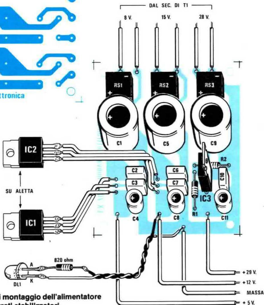
**Fig. 7** Schema pratico di montaggio dell'alimentatore e connessione degli integrati stabilizzatori.
