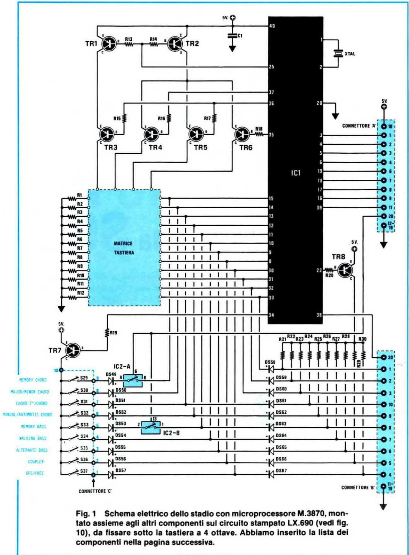
**Fig. 1** Schema elettrico dello stadio con microprocessore M.3870, montato assieme agli altri componenti sul circuito stampato LX.690 (vedi fig. 10), da fissare sotto la tastiera a 4 ottave. Abbiamo inserito la lista dei componenti nella pagina successiva.
