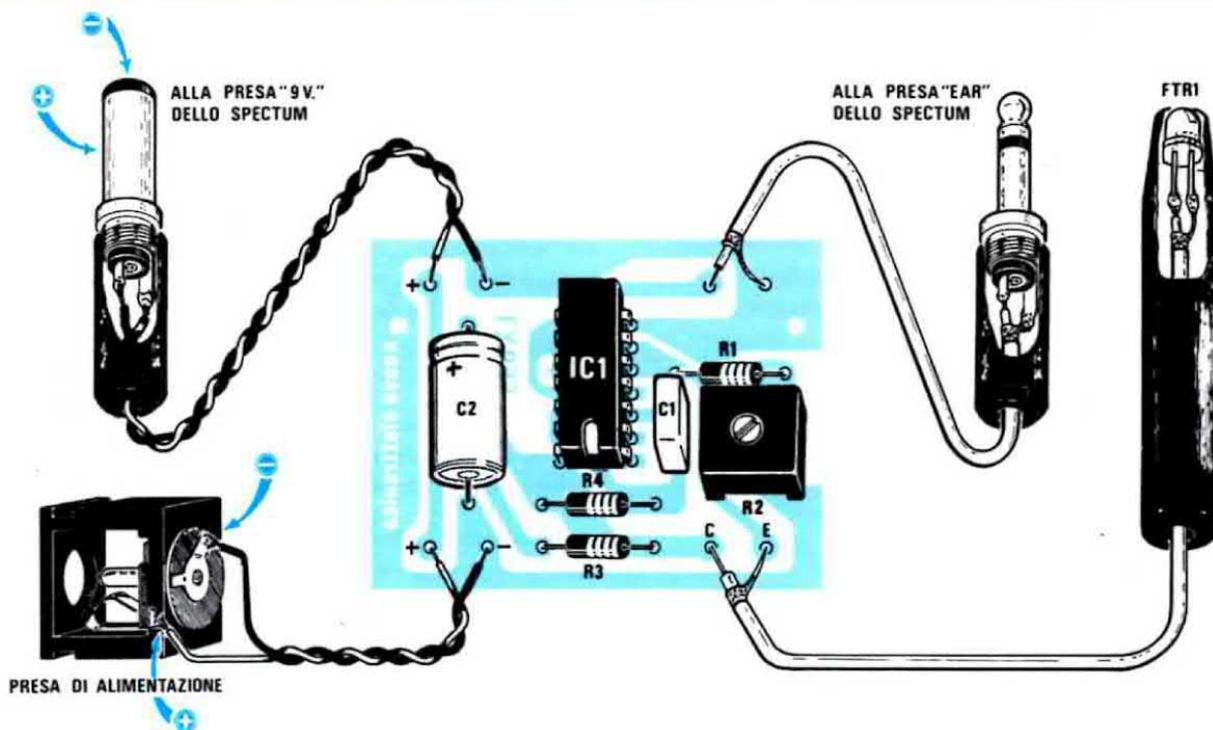
**Fig. 6** Schema pratico di montaggio della penna ottica. Fate attenzione a non invertire i collegamenti nella presa di uscita dei 9 volt e in quella di alimentazione posta in basso a sinistra. Il circuito verrà alloggiato entro un piccolo mobile plastico.
