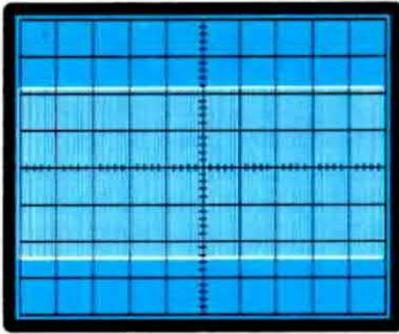
Fig. 13 Valutando la differenza d'ampiezza tra un estremo e l'altro dei due terminali (vedi fig. 12), conoscerete in che rapporto è collegata la presa intermedia.
