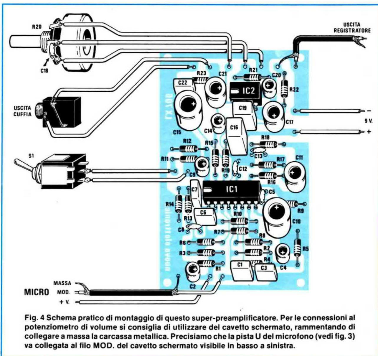
Fig. 4 Schema pratico di montaggio di questo super-preamplificatore. Per le connessioni al potenziometro di volume si consiglia di utilizzare del cavetto schermato, rammentando di collegare a massa la carcassa metallica. Precisiamo che la pista U del microfono (vedi fig. 3) va collegata al filo MOD. del cavetto schermato visibile in basso a sinistra.
