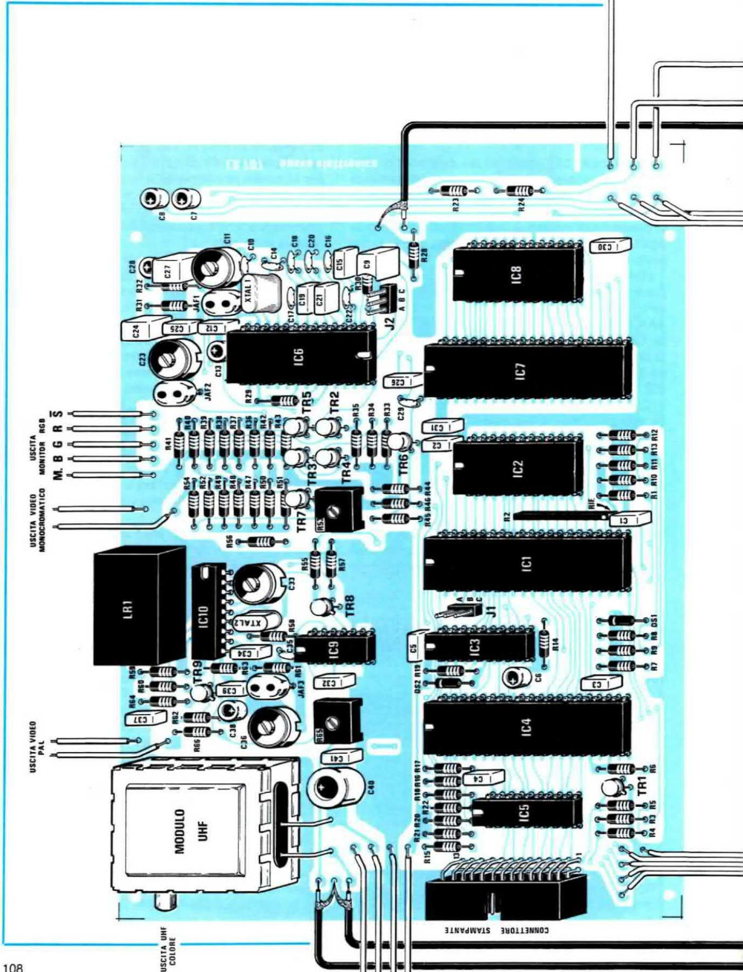
Fig. 5 Schema pratico di montaggio del convertitore Televideo. Le uscite poste in alto servono solo per chi dispone di monitor RGB o bianco e nero, per ogni normale TV il segnale verrà prelevato dal Modulo UHF.
