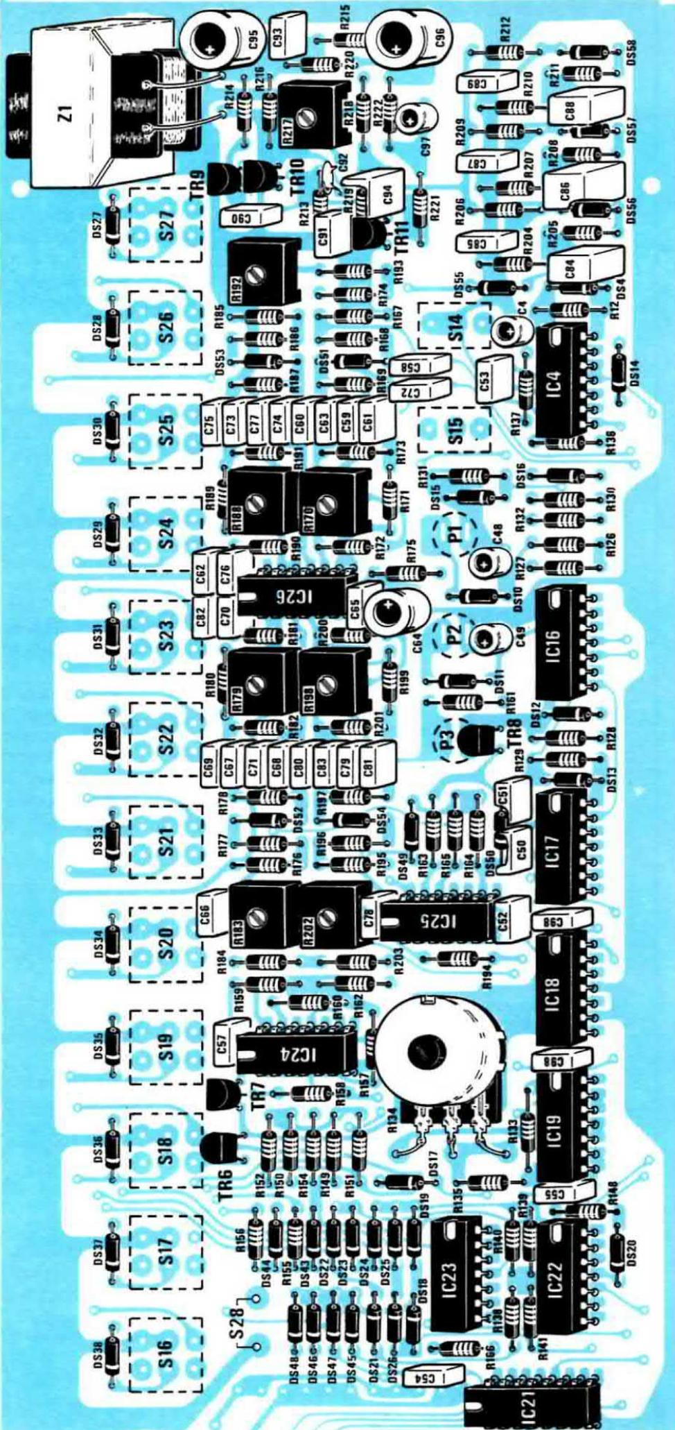
Fig. 16 Schema pratico di montaggio del settore destro del circuito stampato LX.691 e, sotto, la relativa foto. Nei cerchietti tratteggiati con P3 - P2 - P1, dovrete inserire dal lato opposto i tre pulsanti di Break - Start - Stop relativi alla batteria. Grazie a questi chiarissimi disegni, completati anche da quello serigrafico che troverete impresso sul circuito stampato, montare questo progetto sarà facilissimo.
