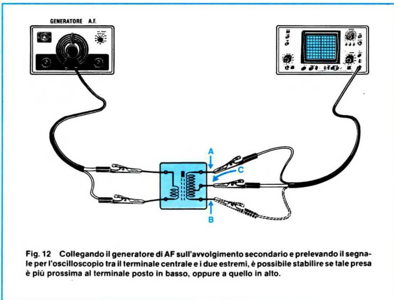
**Fig. 12** Collegando il generatore di AF sull'avvolgimento secondario e prelevando il segnale per l'oscilloscopio tra il terminale centrale e i due estremi, è possibile stabilire se tale presa è più prossima al terminale posto in basso, oppure a quello in alto.
