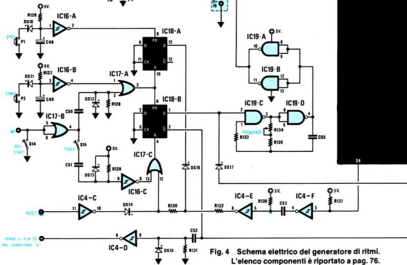
Fig. 4 Schema elettrico del generatore di ritmi. L'elenco componenti è riportato a pag. 76.
