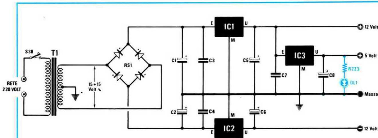
**Fig. 7** Schema elettrico dello stadio alimentatore.
