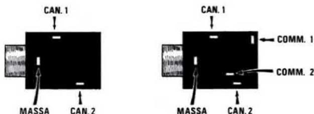
Fig. 7 La presa jack di uscita del microfono di tipo normale dispone di tre soli terminali, se ne possiede cinque, i due in eccesso fanno capo ad un deviatore non utilizzato nel nostro progetto.
