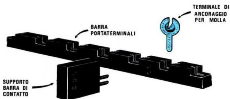
Fig. 12 Nei fori presenti nella barra plastica portaterminali, dovrete innestare i terminali visibili in figura, che vi serviranno per ancorare le molle di contatto.
