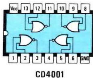
Fig. 4 Connessioni del CD.4001 viste dall'alto.
