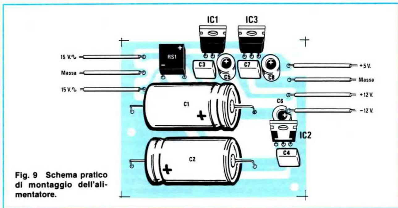
Fig. 9 Schema pratico di montaggio dell'alimentatore.
