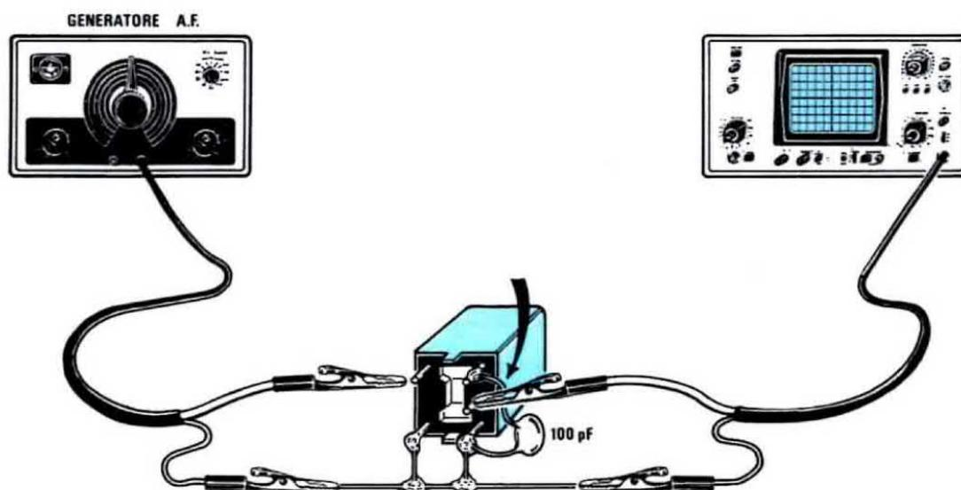
Fig. 11 Per rivelare l'esatta frequenza di accordo di una MF è consigliabile prelevare il segnale da applicare sull'oscilloscopio dalla presa centrale presente sul primario, non dimenticando di applicare sui due terminali esterni il solito condensatore da 100 pF, se nel vano riportato in fig. 6 tale condensatore non risulta presente.
