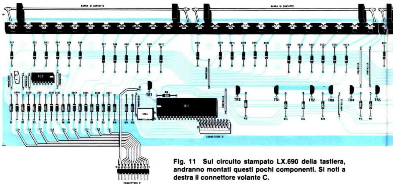
Fig. 11 Sul circuito stampato LX.690 della tastiera, andranno montati questi pochi componenti. Si noti a destra il connettore volante C.
