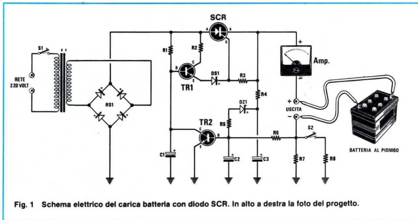
Fig. 1 Schema elettrico del carica batteria con diodo SCR. In alto a destra la foto del progetto.
