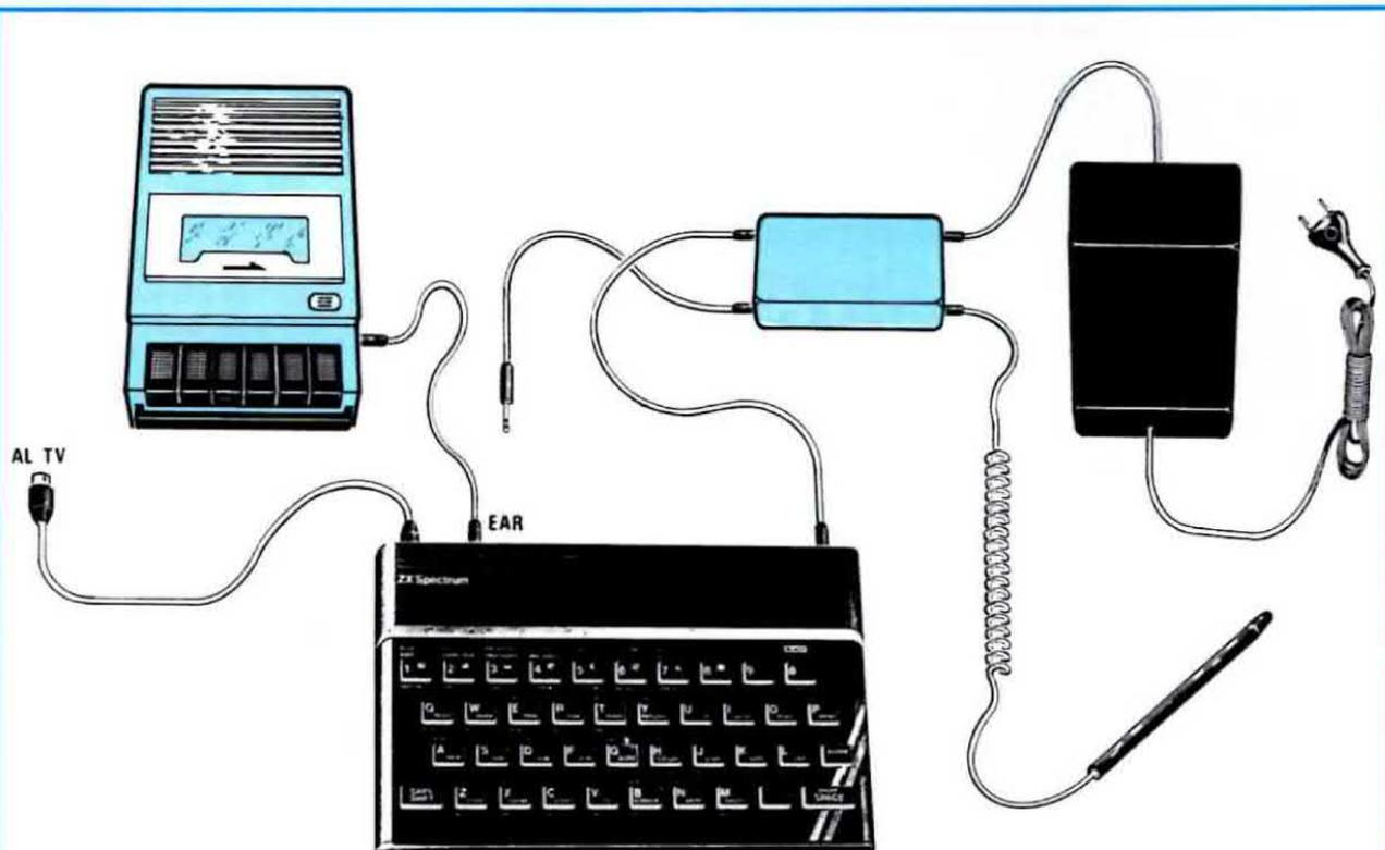
**Fig. 8** Per caricare il programma della penna ottica dalla cassetta fornita nel kit, si dovrà staccare dalla presa EAR del Sinclair la spina proveniente dal mobiletto della penna ottica ed inserire quella del registratore. Una volta caricato il programma, bisognerà inserire nella presa EAR la spina della penna ottica.
