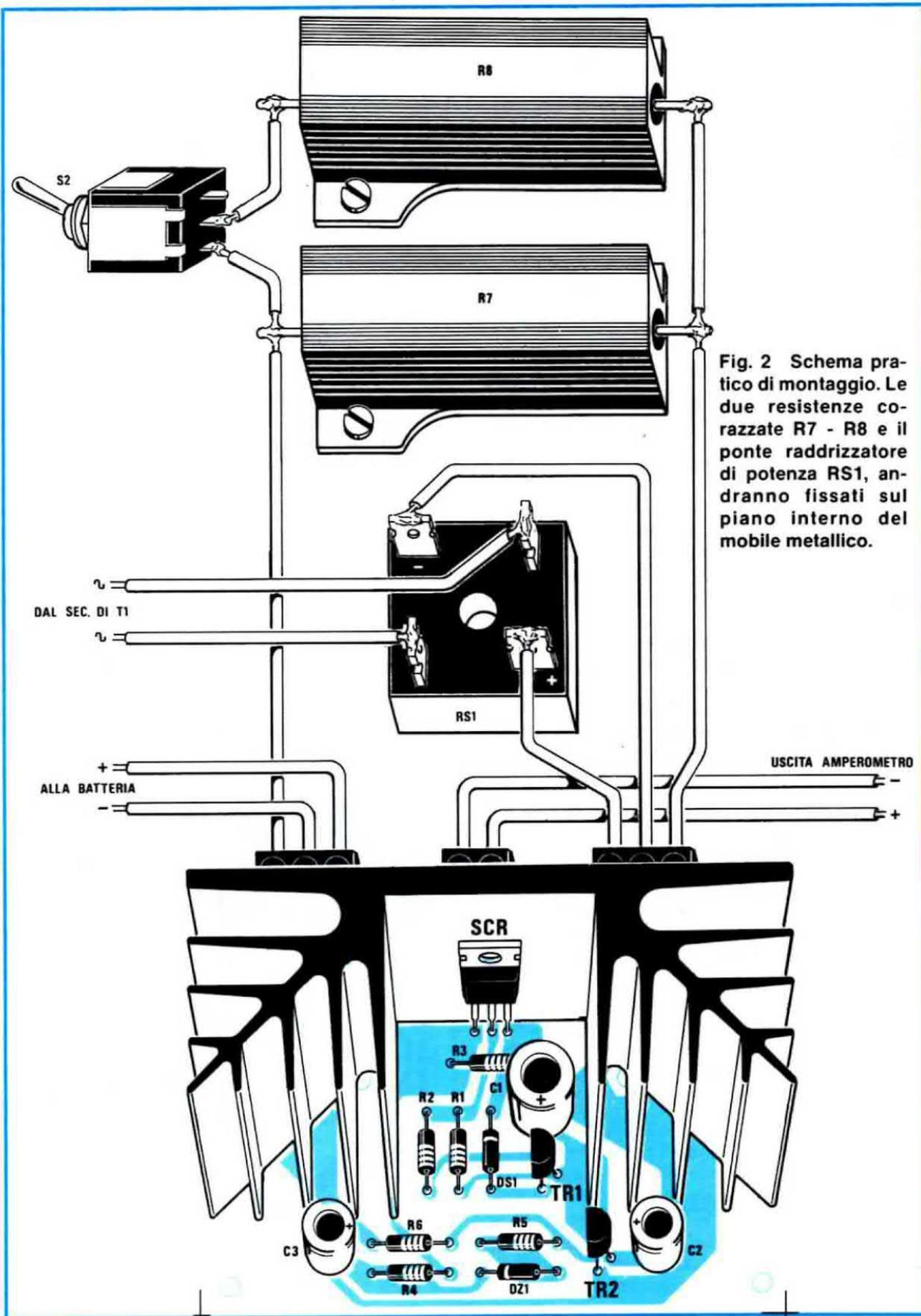
Fig. 2 Schema pratico di montaggio. Le due resistenze cozzate R7 - R8 e il ponte raddrizzatore di potenza RS1, andranno fissati sul piano interno del mobile metallico.
