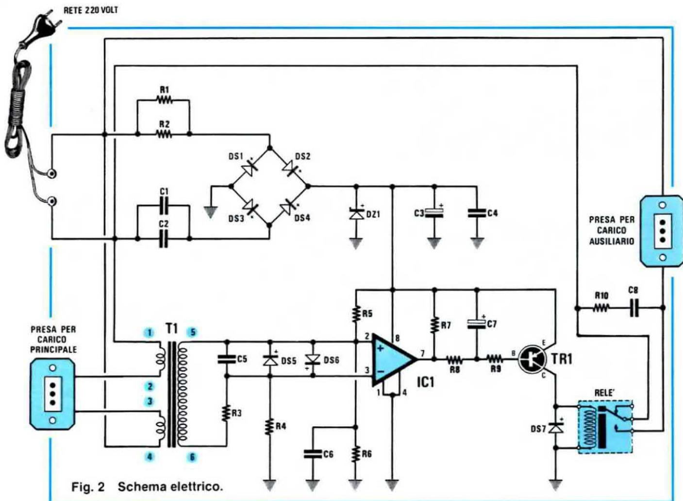
Fig. 2 Schema elettrico.
