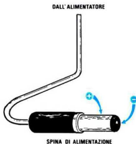
**Fig. 6/A** Nello spinotto collegato all'alimentatore dovrete controllare se il positivo risulta all'esterno ed il negativo nel foro centrale.
