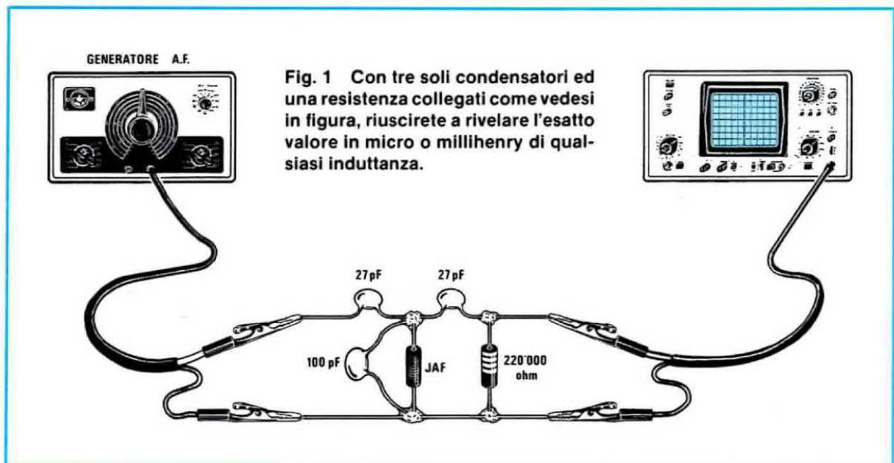
**Fig. 1** Con tre soli condensatori ed una resistenza collegati come vedesi in figura, riuscirete a rivelare l'esatto valore in micro o millihenry di qualsiasi induttanza.
