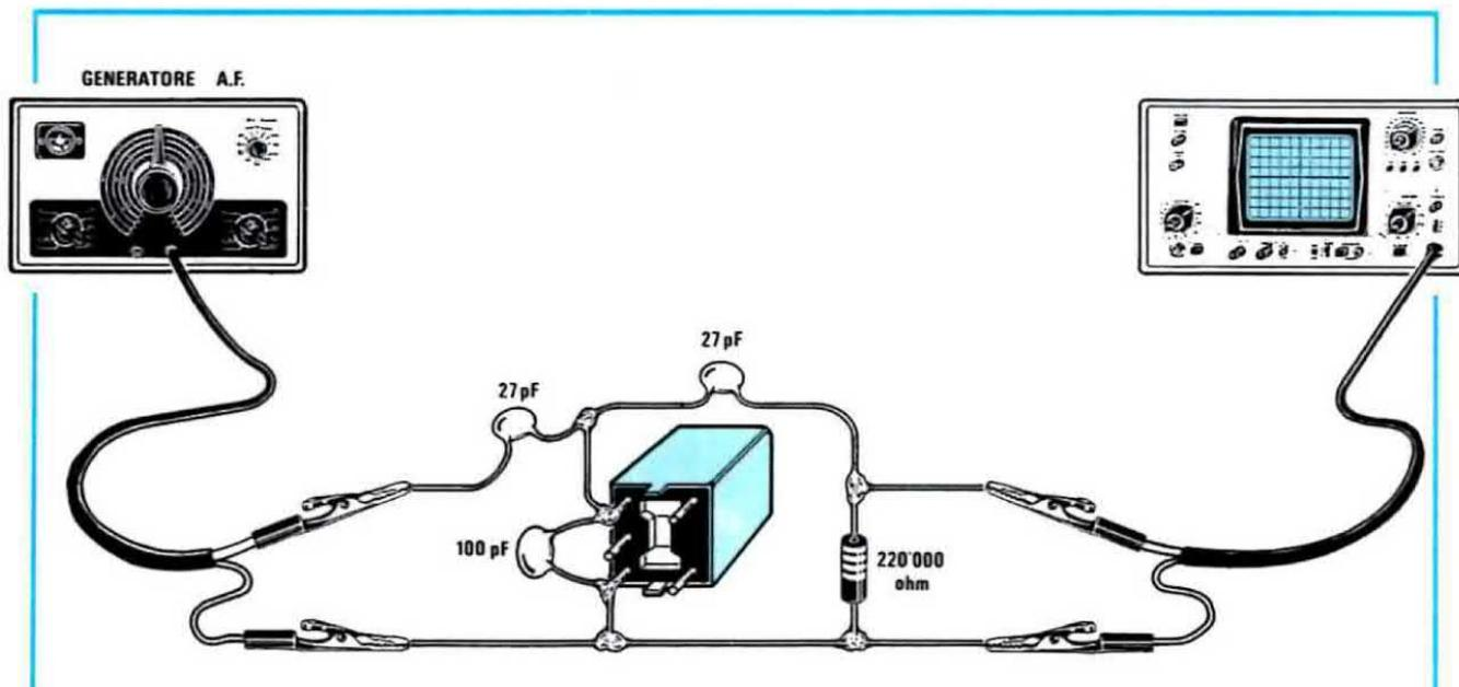
**Fig. 9** Poichè in questa MF non esiste nessun condensatore nel vano indicato in fig. 6, applicherete sugli estremi del primario un condensatore da 100 pF, collegando in serie i due condensatori da 27 pF, come vedesi in fig. 1. Come per le impedenze di AF, dovrete cercare su quale frequenza questo primario si accorda.
