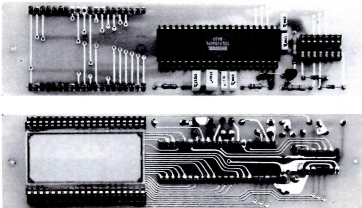
**Fig. 8** Foto del circuito stampato LX.695 visto da entrambi i lati. Come spiegato nell'articolo, il display LCD andrà innestato su due strisce di uno zoccolo a 20 + 20 piedini. Si consiglia di curare le saldature, controllando a fine lavoro che non esistano piste in corto.
