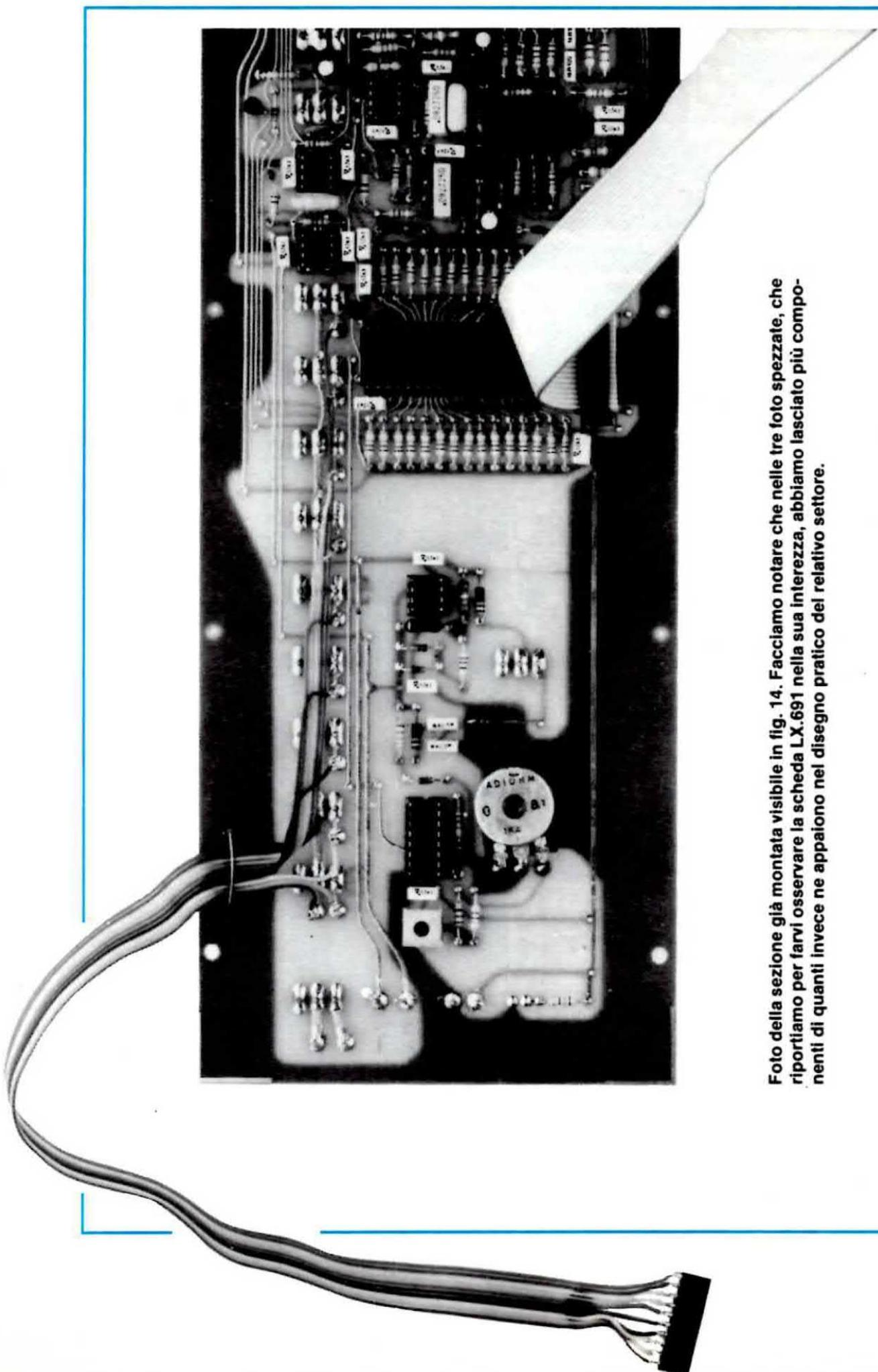
Foto della sezione già montata visibile in fig. 14. Facciamo notare che nelle tre foto spezzate, che riportiamo per farvi osservare la scheda LX.691 nella sua interezza, abbiamo lasciato più componenti di quanti invece ne appaiono nel disegno pratico del relativo settore.
