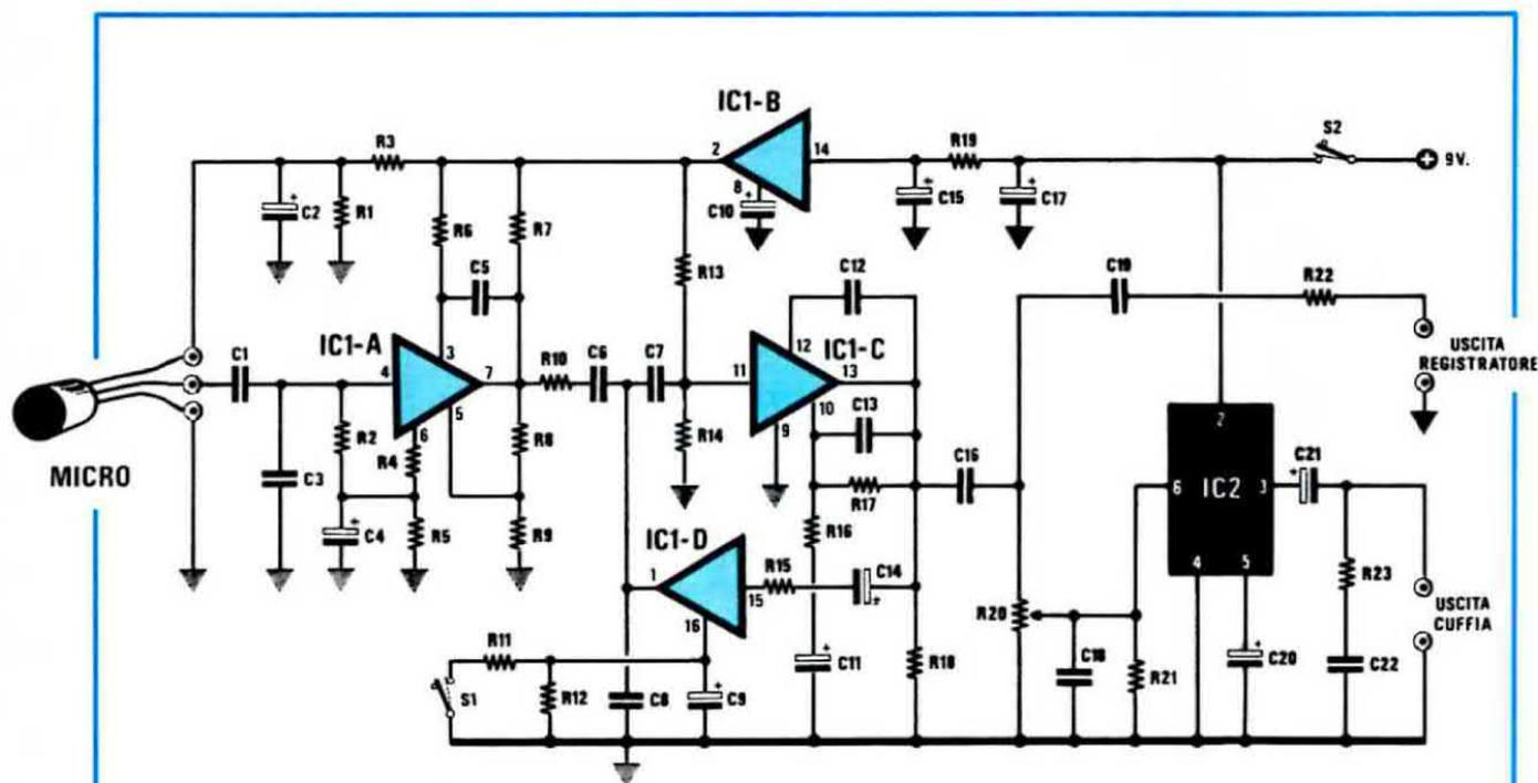
Fig. 2 Schema elettrico del super-preamplificatore.
