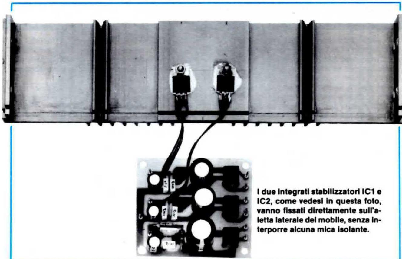
I due integrati stabilizzatori IC1 e IC2, come vedesi in questa foto, vanno fissati direttamente sull'alletta laterale del mobile, senza interporre alcuna mica isolante.
