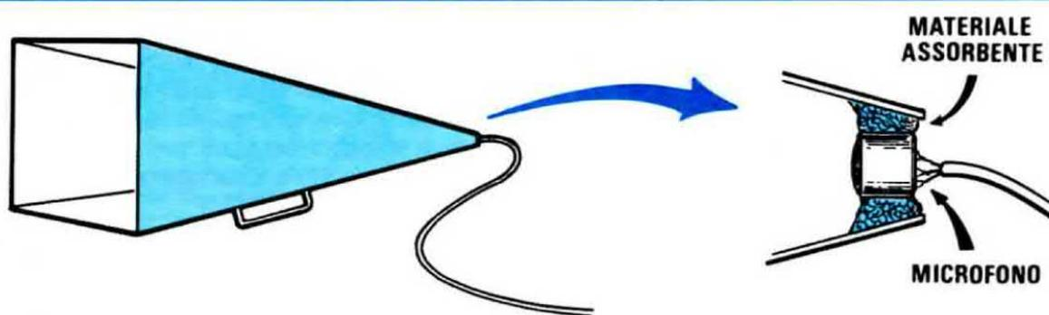
**Fig. 8** Per rendere questo microfono molto direttivo, è necessario completarlo con un imbuto piramidale di diverse dimensioni, che potrete voi stessi ricavare sperimentalmente, fissando alle sue estremità il microfono, dopo aver applicato attorno al suo corpo uno strato di un qualsiasi materiale assorbente.
