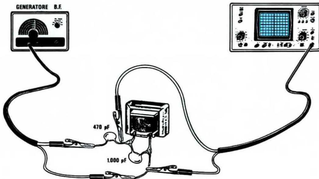
**Fig. 6** Per le misure delle impedenze di BF occorrono solo un condensatore da 470 pF ed uno da 1.000 pF, che andranno collegati all'induttanza come riportato nel disegno, cioè collegando il condensatore da 470 pF verso il generatore di BF. Come per le impedenze di AF, si dovrà trovare l'esatto punto di accordo (vedi figg. 2-3-4).
