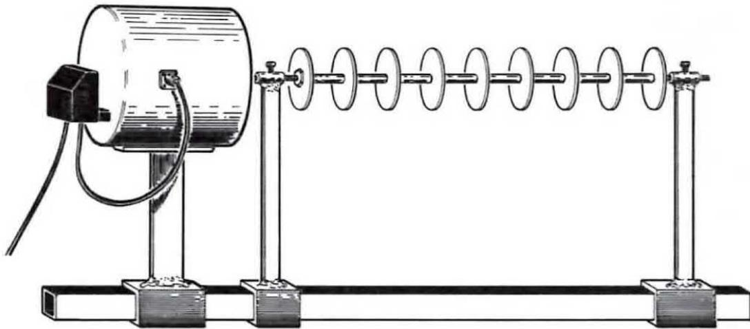
**Fig. 11** Per ricevere il Meteosat, sempre sul retro dell'illuminatore, andrà fissato il nostro preamplificatore LNP-MT/S2 che, risultando a larga banda, si potrà utilizzare anche per la gamma amatoriale da 1,2 a 1,3 GHz.
