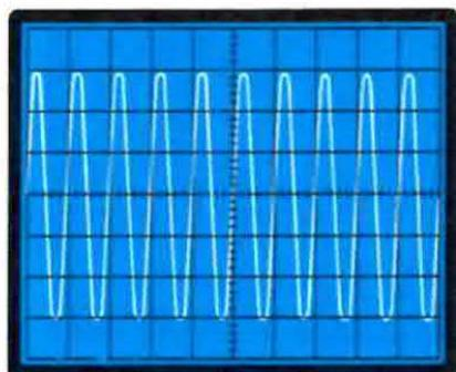
**Fig. 21** Collegate le masse dei due cavetti sul terminale dell'altoparlante e gli altri due terminali sulla resistenza da 100 ohm, dovrete regolare la manopola "uscita ampiezza segnale" del generatore fino ad ottenere, sullo schermo dell'oscilloscopio, un segnale che copra esattamente 6 quadretti in verticale, tenendo la sensibilità sui 0,2 volt per divisione.
