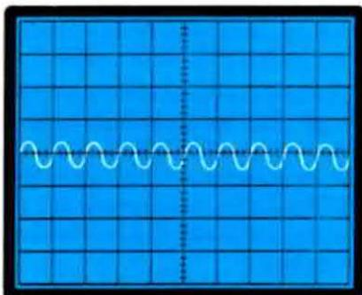
Fig. 23 Posto il puntale sull'altoparlante, il segnale che apparirà sullo schermo dell'oscilloscopio avrà una ampiezza limitata; per questo motivo, dovreste ruotare la manopola "sensibilità verticale" da 0,2 volt per divisione sulla portata inferiore, cioè 20 millivolt per divisione.
