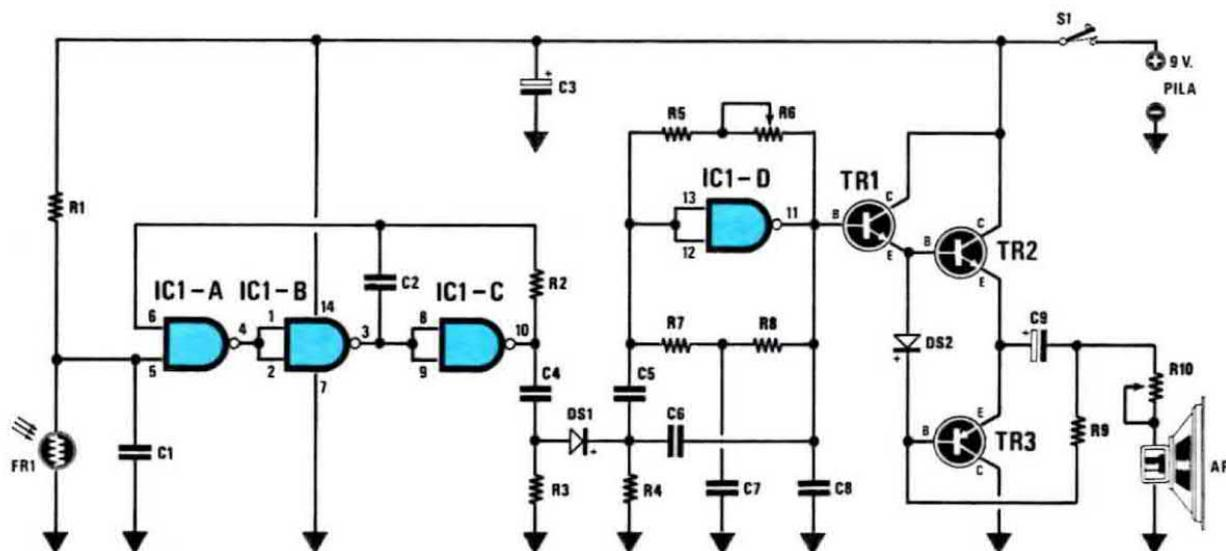
**Fig. 5** Schema elettrico del circuito che simula il suono della goccia d'acqua.
