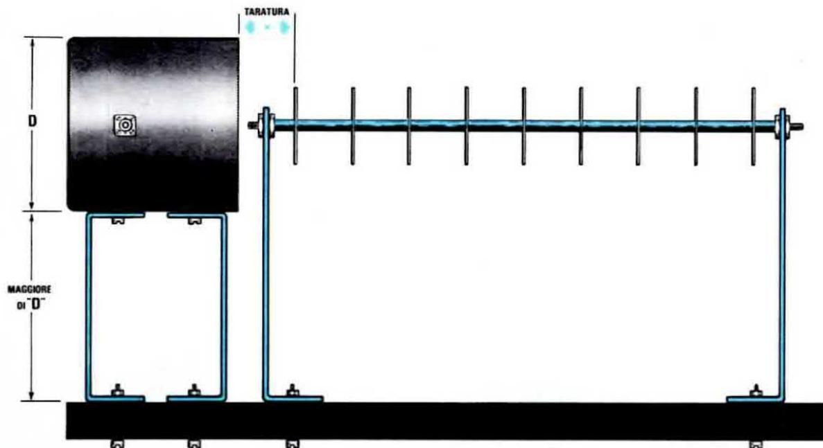
**Fig. 1** Potrete costruire questa antenna utilizzando da un minimo di 12-13 dischetti ad un massimo di 30-33, se volete raggiungere il massimo guadagno. Come vedesi nel disegno, i due supporti del barattolo non dovranno mai risultare inferiori al suo diametro, mentre quelli dei dischetti dovranno risultare logicamente più alti.
