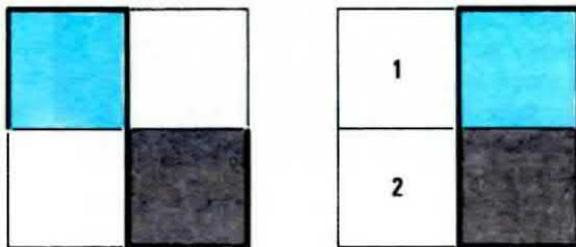
Fig. 19 Con le onde quadre simmetriche, prendendo la semionda positiva e quella negativa, si riescono a riempire totalmente 2 quadretti su 4. Per questo motivo, il valore della tensione efficace si ottiene dividendo sempre per 2 il valore dei volt picco-picco.
