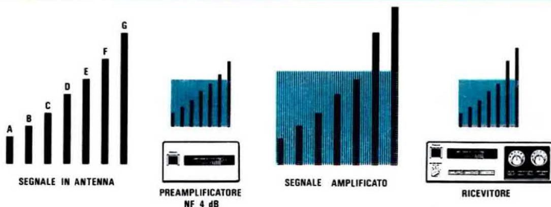
**Fig. 4** Ad esempio se inserite un preamplificatore con guadagno di 10 dB, ma con una noise/figure di 4 dB, vi accorgete subito che la sensibilità risulterà peggiorata, questo perchè il preamplificatore amplificherà di 10 dB le emittenti più forti F-G, ma non le emittenti A-B-C-D-E, risultando la sua NF maggiore di quella del vostro ricevitore.
