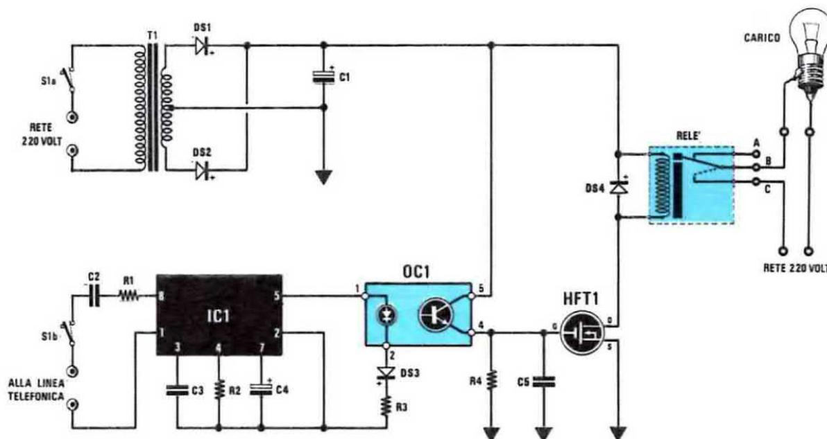
Fig. 2 Schema elettrico.
