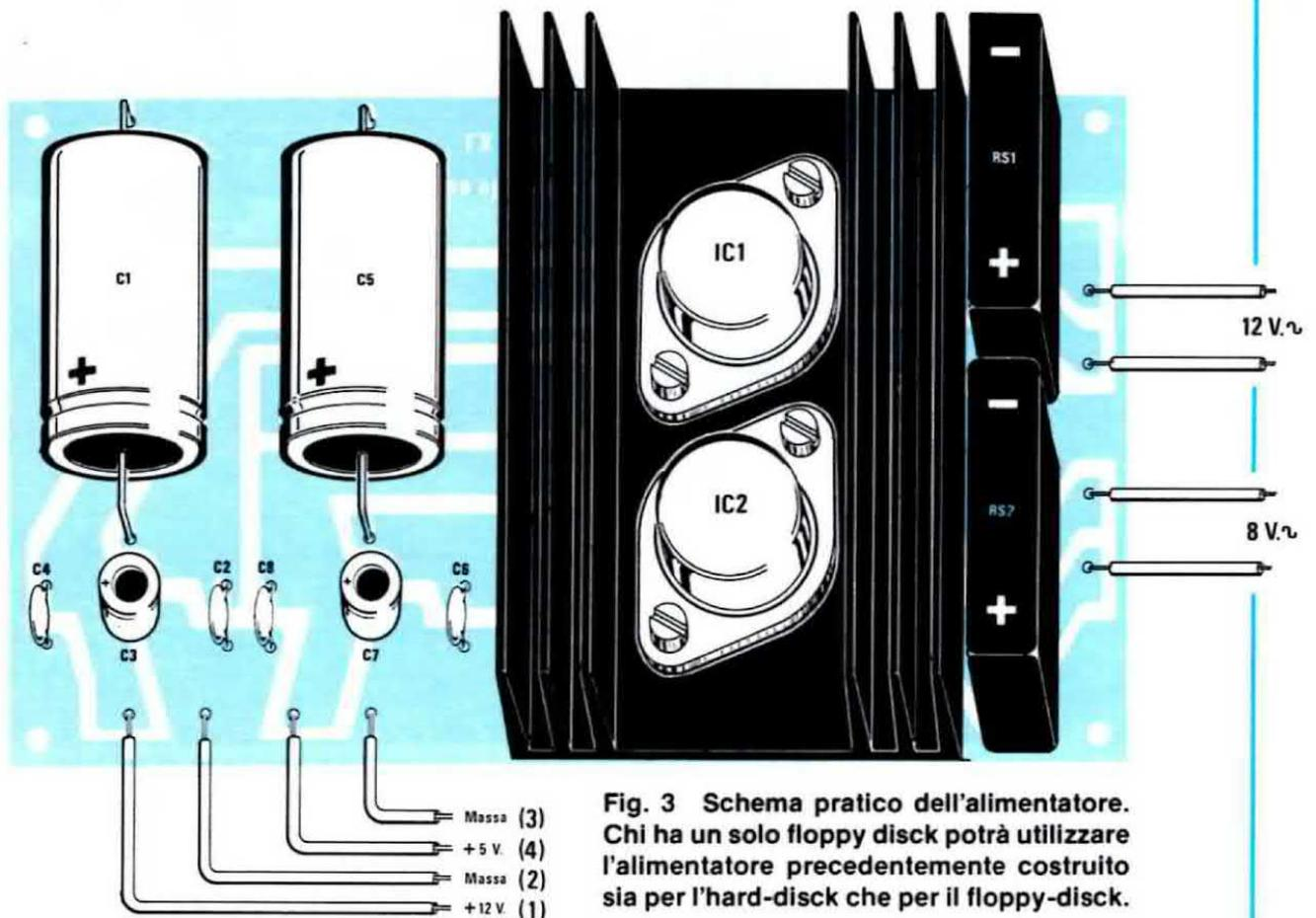
Fig. 3 Schema pratico dell'alimentatore. Chi ha un solo floppy disk potrà utilizzare l'alimentatore precedentemente costruito sia per l'hard-disk che per il floppy-disk.
