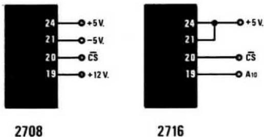
**Fig. 1** Sostituendo nella scheda LX.390 la vecchia eprom 2708 con la nuova 2716, siglata EP.683 perchè già programmata, occorrerà modificare le connessioni dei piedini 21 e 19.
