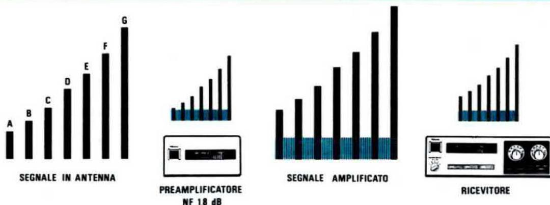
**Fig. 5** Scegliendo invece un preamplificatore con un guadagno inferiore, ma con una noise/figure di soli 1,8 dB, cioè minore di quella posseduta dal vostro ricevitore, come potrete rilevare con un semplice calcolo, la sensibilità del vostro ricevitore migliorerà, tanto da riuscire a captare anche le emittenti A-B-C.
