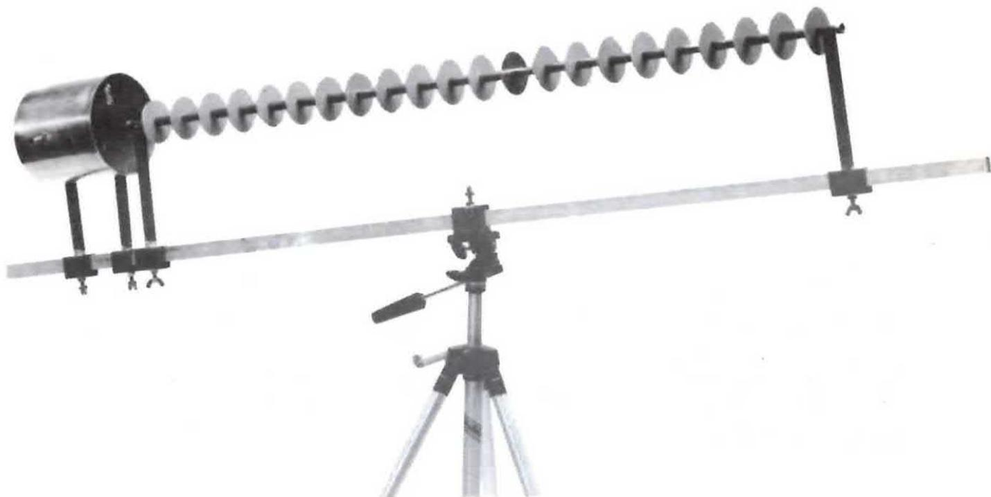
Quest'antenna ha il pregio di risultare molto robusta e assolutamente non critica (vedi le curve di adattamento impedenza a 50 ohm, rivelate sul ponte riflettometrico). Se volete che in inverno il barattolo non si riempia di neve o di acqua, lo potrete riempire con del polistirolo espanso.
