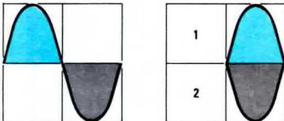
Fig. 17 Con questo semplice esempio figurativo potrete comprendere più facilmente perchè, per ottenere i volt efficaci, occorra dividere per 2,82 i volt picco-picco di un'onda sinusoidale. Come vedesi in figura, abbiamo 2 quadretti vuoti più un 0,82 sugli altri due.
