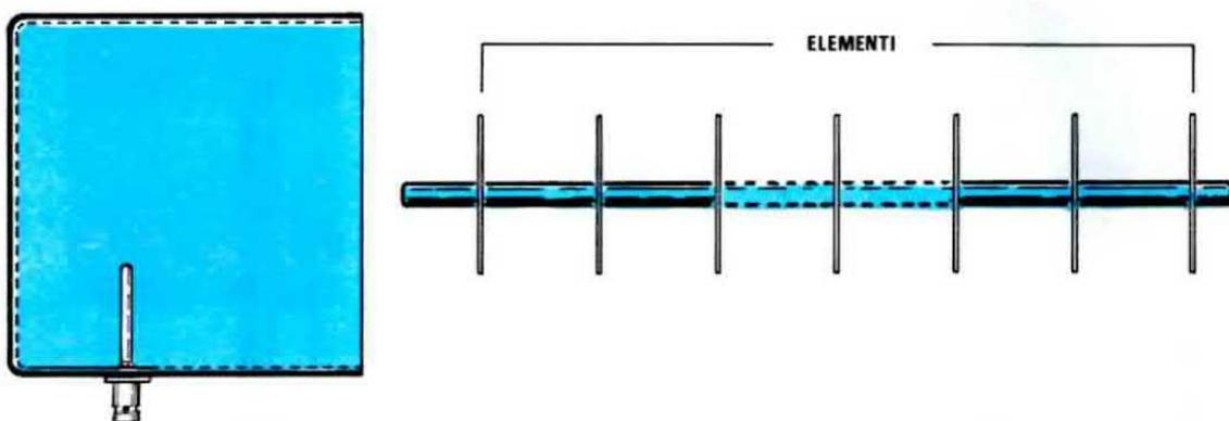
**Fig. 8** Per poter realizzare facilmente questa antenna per le due gamme da noi prescelte, vi forniremo l'illuminatore a barattolo, il tubetto in rame per l'antenna, 30 dischetti già forati e i relativi distanziatori.
