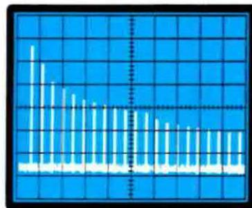
**Fig. 3** Il generatore AF da utilizzare per la elettromagnetoterapia deve possedere la caratteristica di generare contemporaneamente tutte le frequenze richieste. Nella foto, la gamma coperta vista all'analizzatore di spettro.
