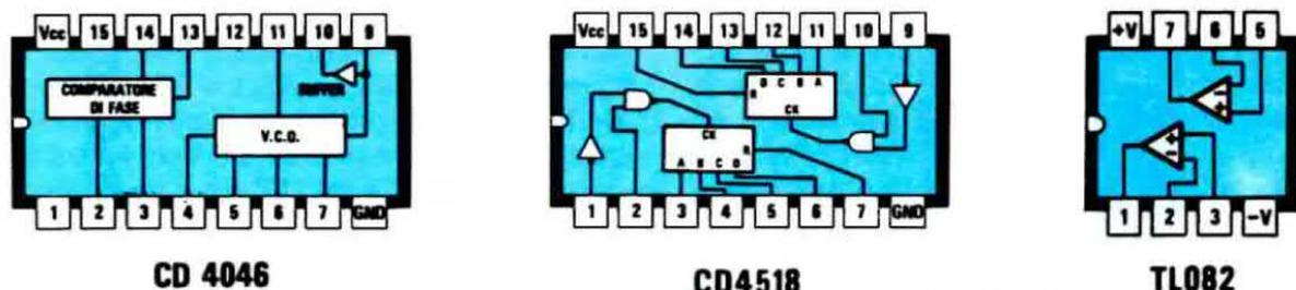
**Fig. 2** Connessioni degli Integrati utilizzati in questo progetto, visti dall'alto, e del transistor visti invece dal basso, cioè dal lato in cui i terminali fuoriescono dal corpo. Negli integrati la scritta GND significa "massa" o negativo di alimentazione, mentre Vcc significa tensione positiva di alimentazione.
