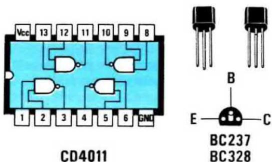
Fig. 6 Connessioni dell'integrato viste dall'alto e dei transistor visti invece dal basso.
