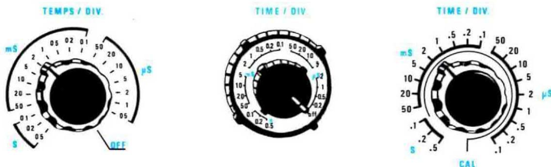
**Fig. 1** In ogni oscilloscopio la manopola del TIME/BASE dispone di una propria suddivisione dei tempi, in Secondi - milliSecondi - microSecondi come qui sopra riportato. Come spiegato nell'articolo, conoscendo il "tempo" e controllando quanti quadretti occupa in orizzontale una sola sinusoide, potrete rilevare con una buona approssimazione l'esatta FREQUENZA.
