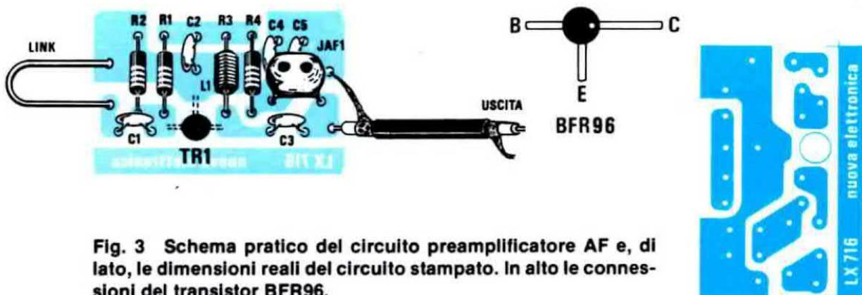
**Fig. 3** Schema pratico del circuito preamplificatore AF e, di lato, le dimensioni reali del circuito stampato. In alto le connessioni del transistor BFR96.
