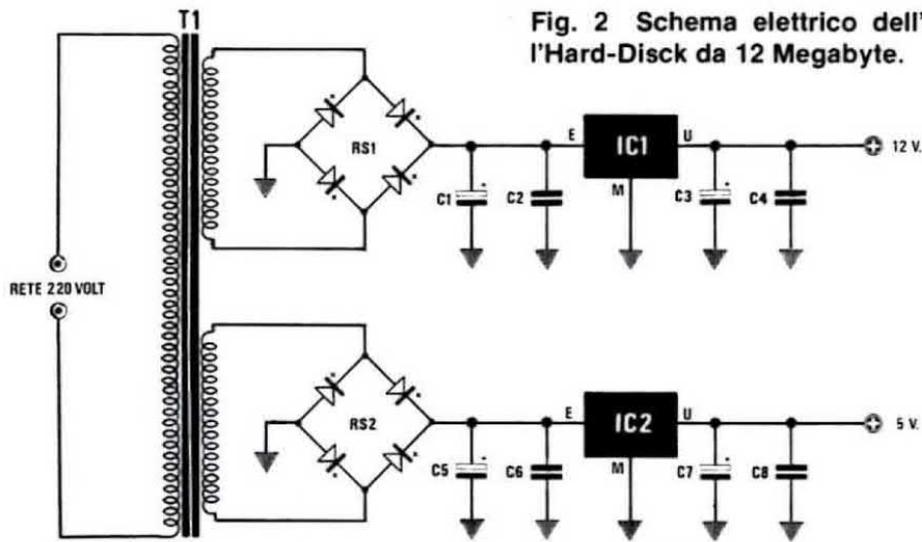
Fig. 2 Schema elettrico dell'alimentatore per l'Hard-Disk da 12 Megabyte.
