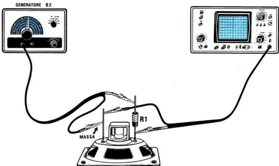
Fig. 22 Non toccando più la manopola "uscita ampiezza segnale" del generatore di BF, dovreste spostare il puntale dell'oscilloscopio dopo la resistenza R1, cioè, come vedesi in figura, direttamente sull'altro terminale della bobina mobile dell'altoparlante.
