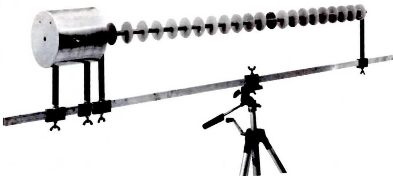
Come vedesi in questa foto, abbiamo utilizzato come supporto base di sostegno un trafilato rettangolare in alluminio, e realizzato dei supporti mobili per sostenere l'illuminatore a barattolo, per ricercare sperimentalmente l'esatta distanza a cui porre l'imboccatura dell'illuminatore dal primo dischetto, in modo da ottenere qualche dB in più di guadagno.
