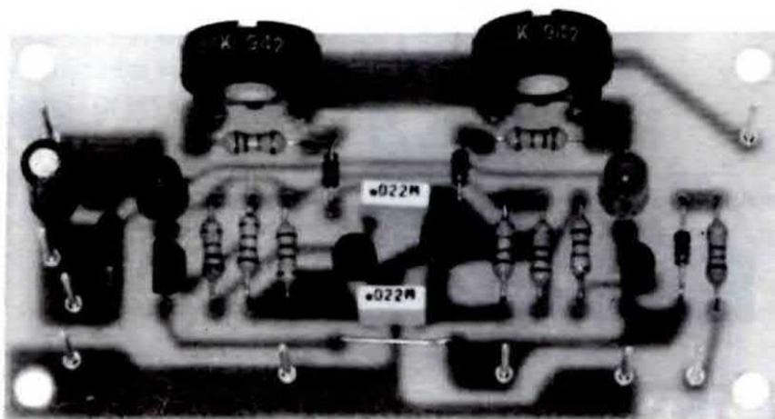
In pratica, se quando inseriremo un transistor in prova si accenderanno entrambi i diodi led, significherà che il transistor è in **corto**, se non se ne accenderà nessuno che la giunzione è **bruciata**, cioè che il transistor è aperto, se se ne accenderà uno solo, che il transistor, un NPN o un PNP, è efficiente.
