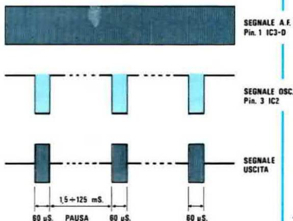
**Fig. 4** Il generatore deve essere in grado di fornire queste frequenze per una durata massima di 60 microsecondi, intervallate da una "pausa" che può variare da un minimo di 1,5 ad un massimo di 125 millisecondi.
