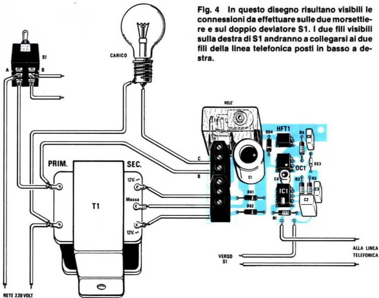
Fig. 4 In questo disegno risultano visibili le connessioni da effettuare sulle due morsettiere e sul doppio deviatore S1. I due fili visibili sulla destra di S1 andranno a collegarsi ai due fili della linea telefonica posti in basso a destra.
