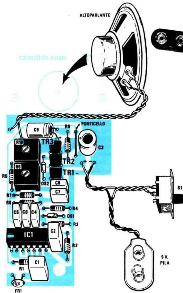
Fig. 7 Schema pratico di montaggio. Non dimenticatevi di effettuare il ponticello visibile tra la R9 e C3 e di collocare tutti i transistor con la parte piana rivolta verso il condensatore C9 posto orizzontalmente. Come riportato nell'articolo, il circuito funziona solo oscurando la fotoresistenza.
