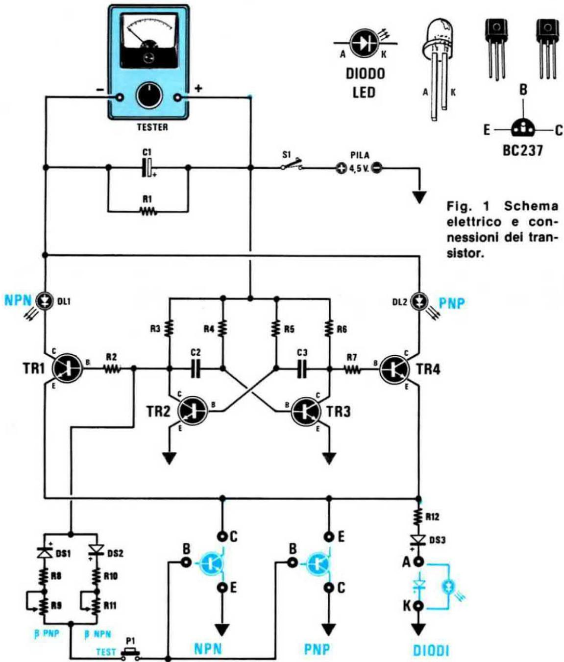
Fig. 1 Schema elettrico e connessioni dei transistor.
