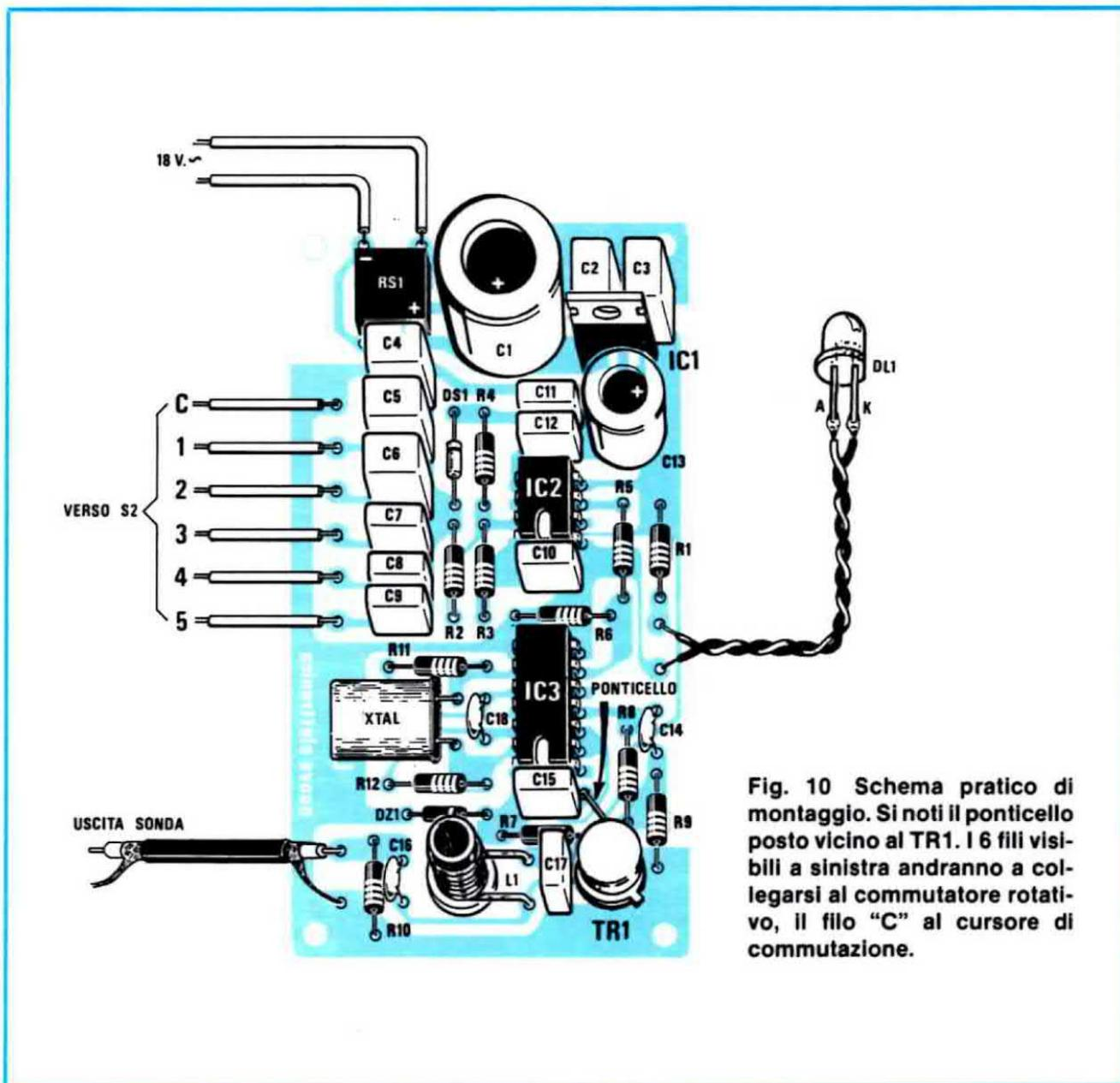
Fig. 10 Schema pratico di montaggio. Si noti il ponticello posto vicino al TR1. I 6 fili visibili a sinistra andranno a collegarsi al commutatore rotativo, il filo "C" al cursore di commutazione.
