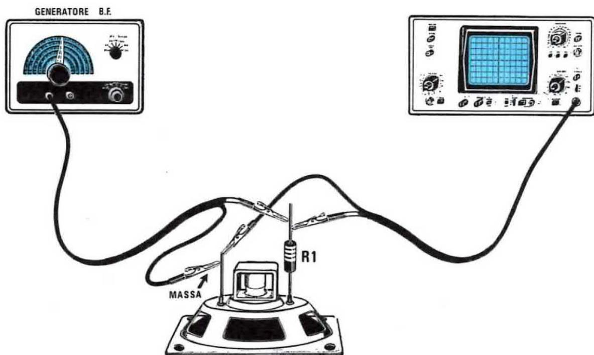
**Fig. 20** Per misurare l'esatto valore d'impedenza di un altoparlante o di una cuffia, occorre solo una normale resistenza da 100 ohm 1/2 watt ed un generatore di BF sintonizzato sulla frequenza di 1.000 Hz onda sinusoidale.
