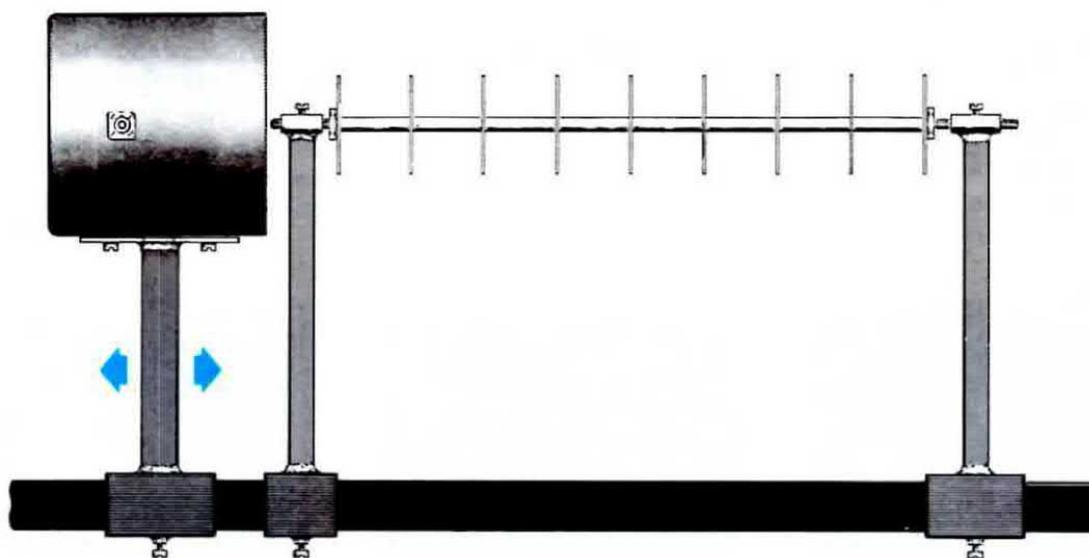
**Fig. 10** Lo spostamento in avanti o indietro dell'illuminatore per riuscire a guadagnare qualche dB, sarà sempre di pochi centimetri. Montando stabilmente l'illuminatore, in modo che la distanza della sua imboccatura risulti pari a quella che separa ogni dischetto (vedi S e S in fig. 7), otterrete già un elevato guadagno.
