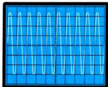
Fig. 24 Così facendo aumenterà l'ampiezza in verticale. A questo punto dovreste contare quanti quadretti e "tacche" di suddivisione copre la sinusoidale (sono presenti 4 tacche che suddividono il quadretto in 5 parti) e con la formula riportata ne potrete calcolare l'impedenza.
