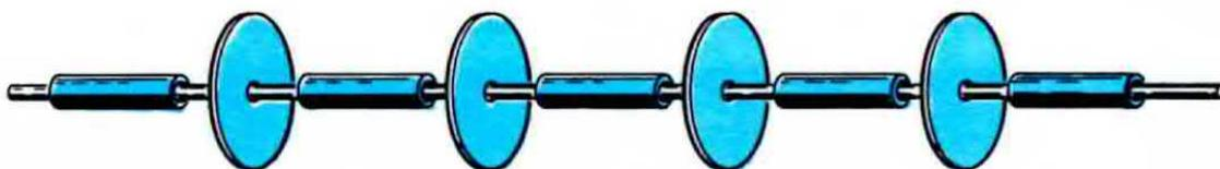
**Fig. 9** Nell'asta di sostegno centrale dovreste inserire un dischetto ed un distanziatore. Davanti al primo e dopo l'ultimo dischetto (vedi fig. 1), dovreste inserire un distanziatore più corto.
