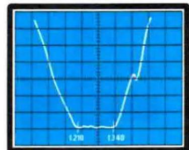
**Fig. 14** Ponendo l'illuminatore a 30 mm. dal primo dischetto, come vedesi in figura, si restringerà di circa 30-60 MHz.
