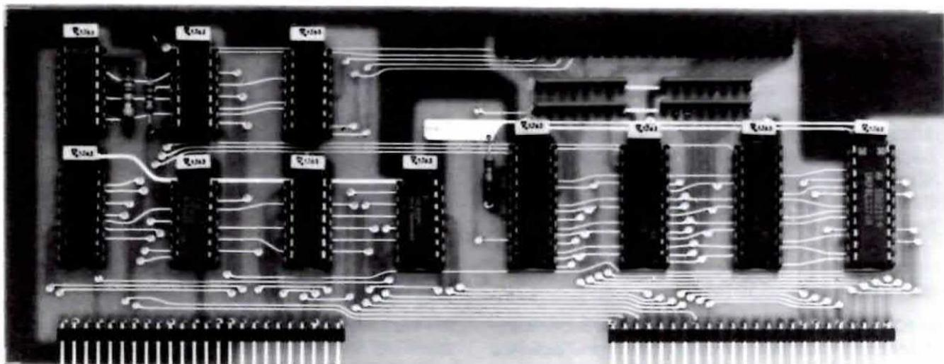
Per inserire nel vostro computer questo Hard-Disk da 12 Megabyte è necessario realizzare questa scheda siglata LX.683, togliere dalla scheda LX.390 la vecchia Eprom 1390, o 2390, e sostituirla con quella siglata EP.683. Leggere a pag. 47 le istruzioni riguardanti la sostituzione di questa nuova Eprom.
