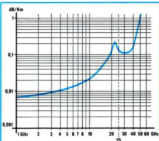
**Fig. 2** Come vedesi in questo grafico, alla frequenza di 1 GHz si ha un'attenuazione di 0,01 dB per Km., per raggiungere i 0,1 dB alla frequenza di 20 GHz. Sul 22,23 GHz si ha una attenuazione massima di 0,2 dB per Km., in quanto tale frequenza viene attenuata dal vapor acqueo.
