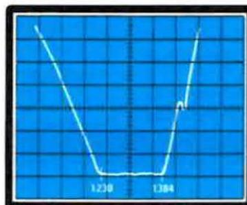
**Fig. 13** Stessa antenna, con dischetti spazati sempre di 57 mm., ma con la bocca dell'illuminatore posta a 40 mm. dal primo dischetto.
