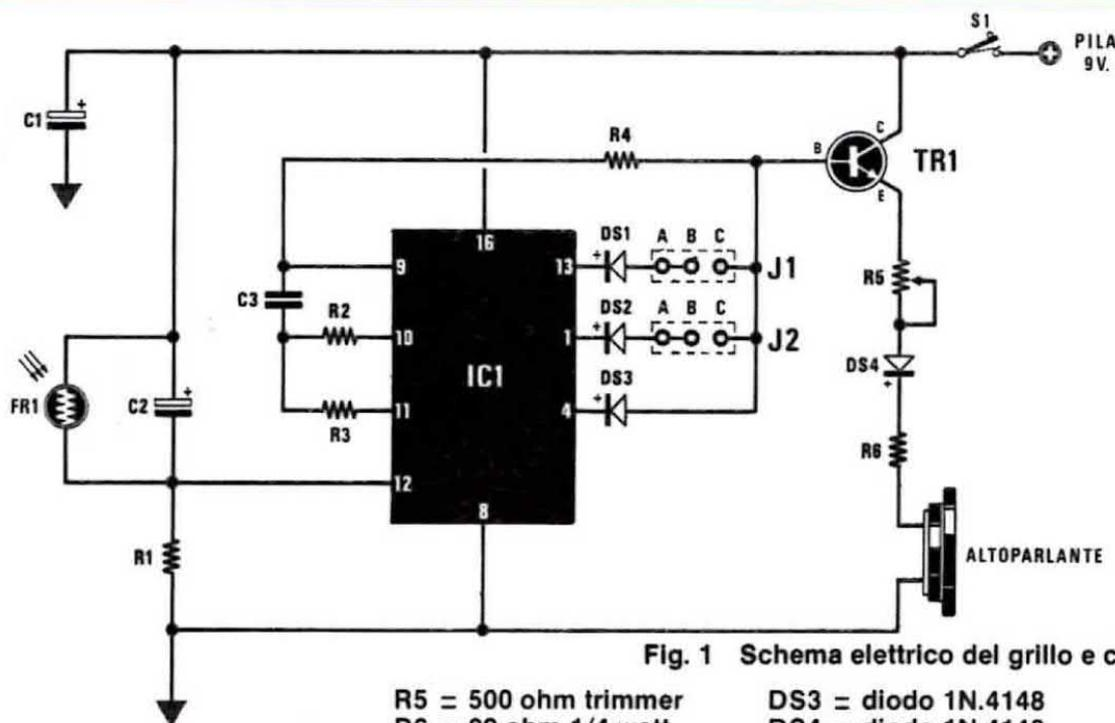
Fig. 1 Schema elettrico del grillo e cicala.
