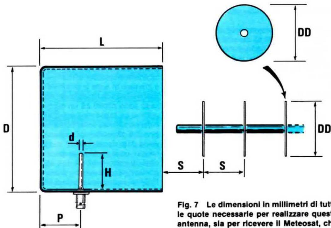
Fig. 7 Le dimensioni in millimetri di tutte le quote necessarie per realizzare questa antenna, sia per ricevere il Meteosat, che per la gamma radioamatoriale del 1,3 GHz, sono riportate nell'articolo.
