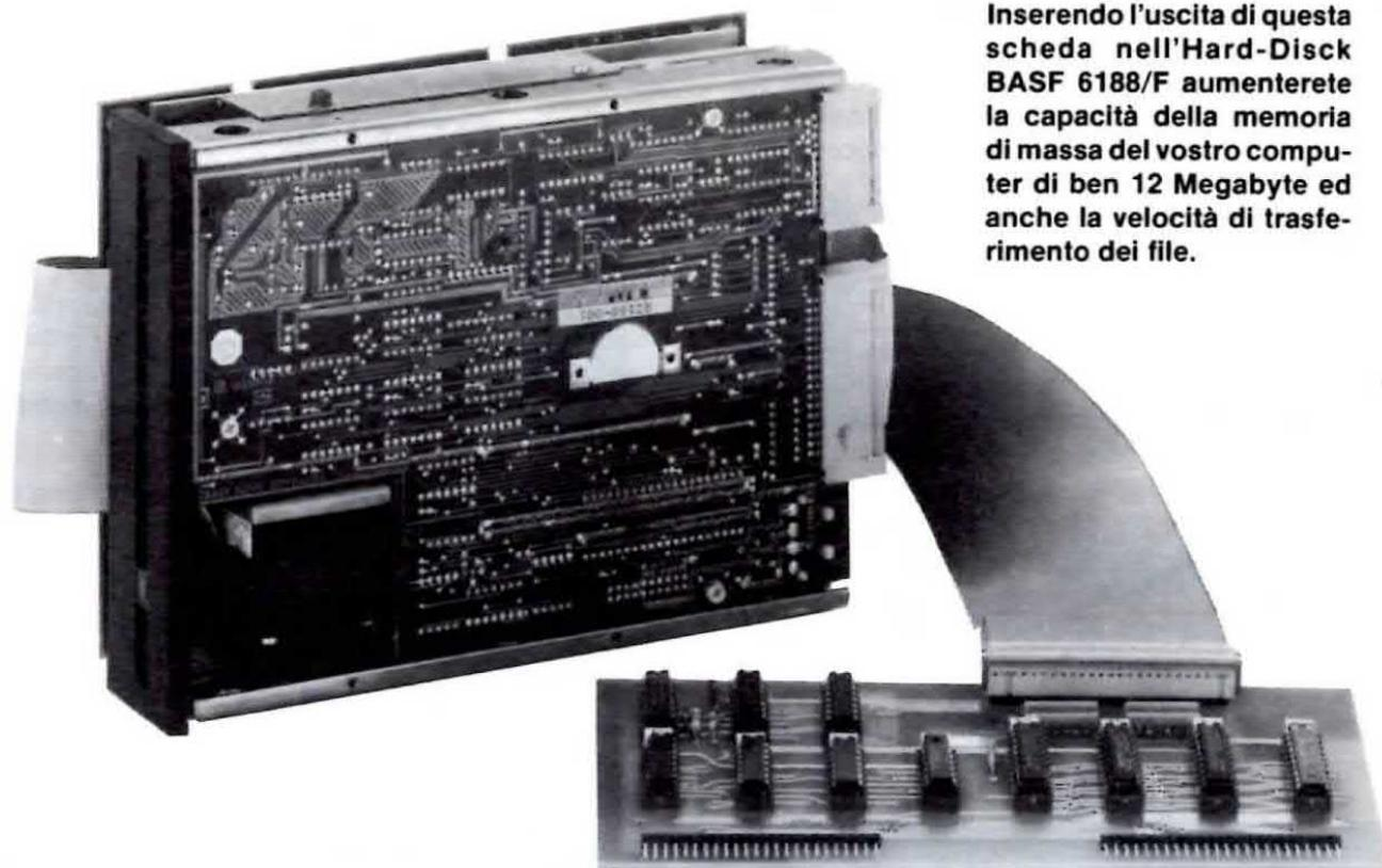
Inserendo l'uscita di questa scheda nell'Hard-Disk BASF 6188/F aumenterete la capacità della memoria di massa del vostro computer di ben 12 Megabyte ed anche la velocità di trasferimento dei file.
