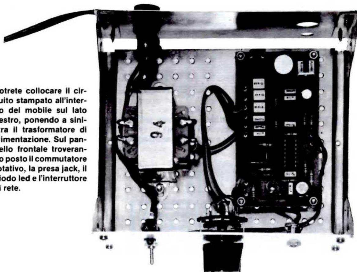
**Potrete collocare il circuito stampato all'interno del mobile sul lato destro, ponendo a sinistra il trasformatore di alimentazione. Sul pannello frontale troveranno posto il commutatore rotativo, la presa jack, il diodo led e l'interruttore di rete.**
