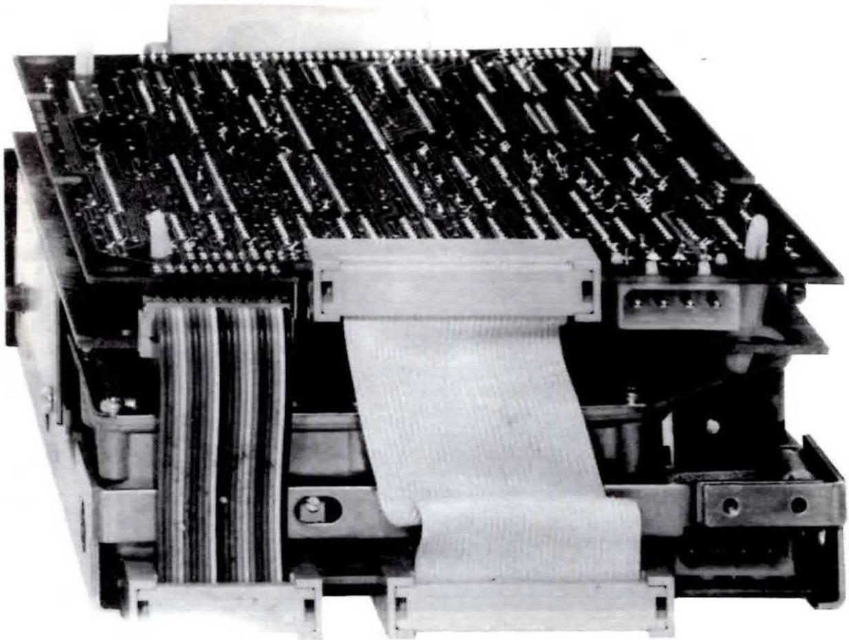
Fig. 6 Sulla parte posteriore dell'Hard-Disk troverete due piattine già collegate alla scheda "hard-disk-controller" e in basso a destra e sulla scheda in alto troverete inoltre due connettori maschi necessari per le alimentazioni. Come vedesi nel disegno, nel connettore B posto in basso, i 5 volt sono a sinistra e i 12 volt a destra, nel connettore A posto in alto, le tensioni risultano invece invertite.
