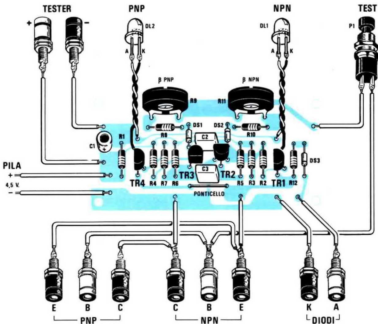
Fig. 3 Schema pratico di montaggio del provatransistor dinamico. Si noti il ponticello che dovrete effettuare sotto al condensatore C3 e il verso in cui dovrà essere posizionata la parte piana dei transistor. Come spiegato nell'articolo, nelle due bocche poste in alto a sinistra andrà inserito il nostro tester commutato sulla portata CC, in una delle seguenti scale: 3 volt - 2,5 - 1 - 0,3 volt.
