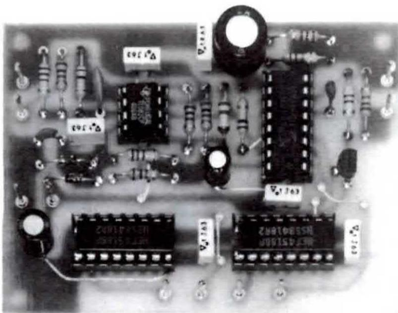
Applicando sul vostro frequenzimetro questo accessorio, potrete leggere con una risoluzione di 0,001 Hz tutte le frequenze al di sotto del 500 Hz. Ad esempio, se ora il vostro frequenzimetro misurando i 50 Hz della rete oscilla su valori di 51-50-49 Hz, applicando questo moltiplicatore leggerete esattamente 50,000 Hz.
