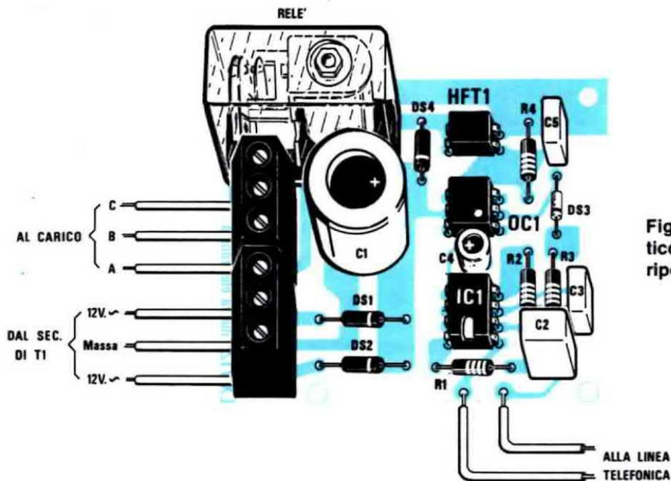
Fig. 3 Schema pratico di montaggio del ripetitore telefonico.
