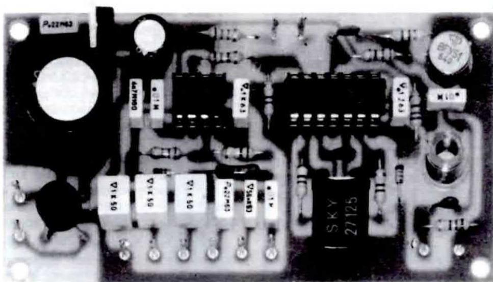
**A realizzazione ultimata il vostro montaggio dovrà presentarsi come vedesi in questa foto. In questo montaggio abbiamo inserito un quarzo CB da 27.125 KHz che, come saprete, risultando di 3<sup>a</sup> armonica oscillerà sul 9 MHz circa.**
