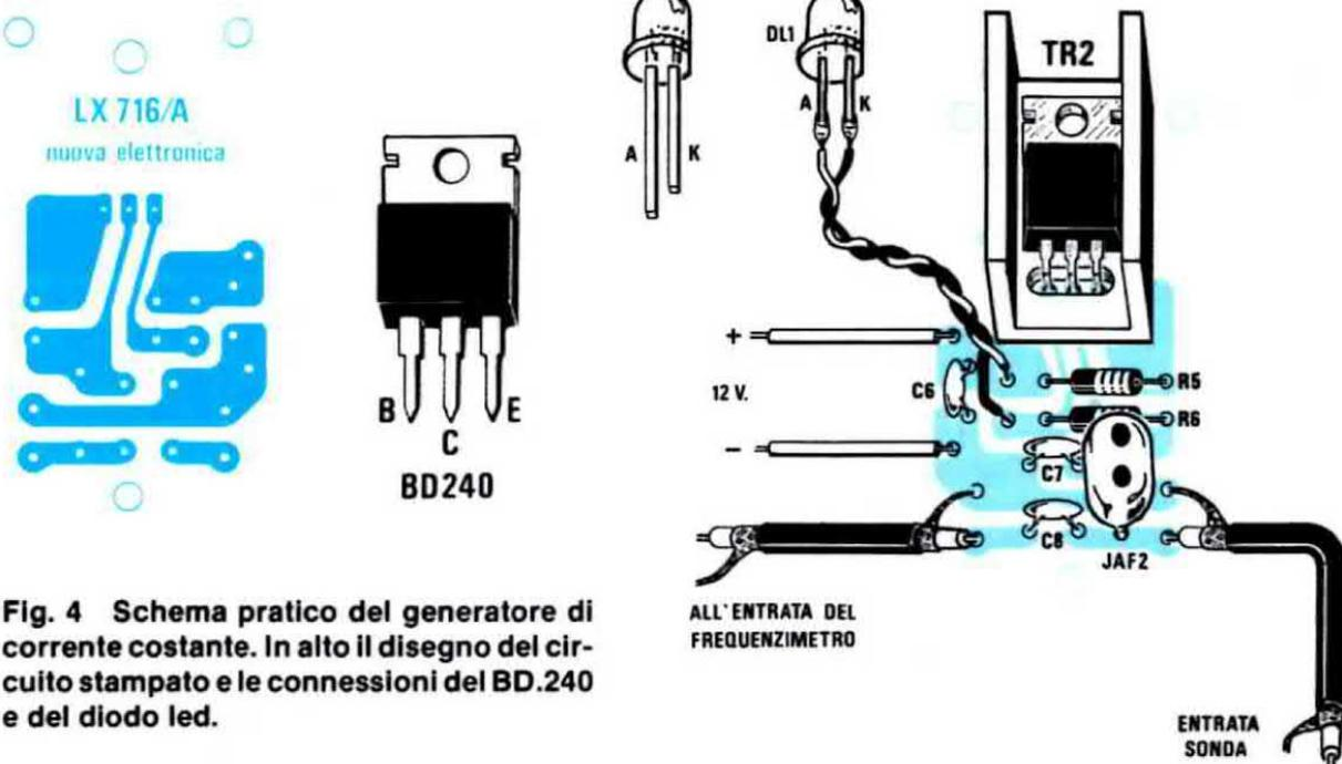
**Fig. 4** Schema pratico del generatore di corrente costante. In alto il disegno del circuito stampato e le connessioni del BD.240 e del diodo led.
