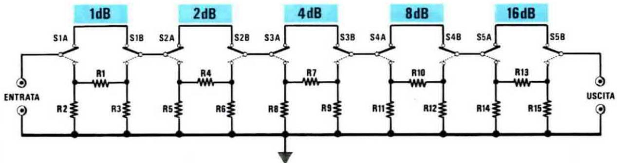
Fig. 1 Schema elettrico dell'attenuatore ad impedenza costante. Qui sotto, la lista componenti per i tre valori più comuni di impedenza, cioè 50 - 75 - 600 ohm.
