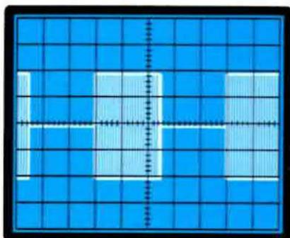
**Fig. 23** Per ottenere questa figura, è sufficiente premere i pulsanti **MANUALE** e **BURST**. Se collegate l'**USCITA SINCR.** all'ingresso "**Sincr.EXT**" dell'oscilloscopio, l'immagine rimarrà ferma.
