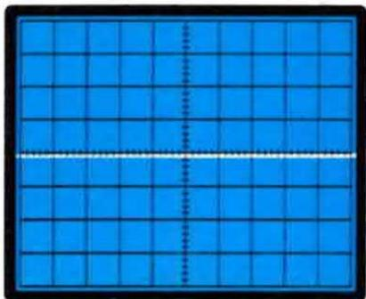
**Fig. 15** Per tarare il generatore di funzioni, dovrete spostare il deviatore dell'oscilloscopio AC-GND-CC in posizione GND e ruotare la manopola verticale, per portare la traccia luminosa al centro dello schermo.
