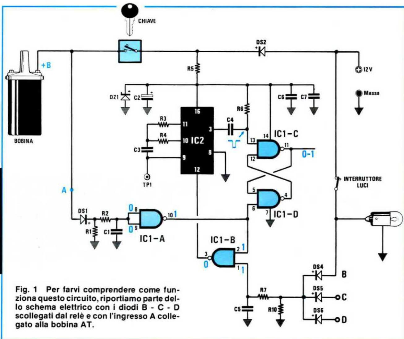
Fig. 1 Per farvi comprendere come funziona questo circuito, riportiamo parte dello schema elettrico con i diodi B - C - D scollegati dal relè e con l'ingresso A collegato alla bobina AT.
