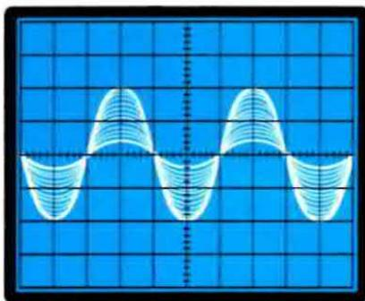
**Fig. 25** La stessa frequenza di fig. 24, sempre modulata in ampiezza, come verrà visualizzata sullo schermo dell'oscilloscopio ponendo la manopola del Time/Base sulla portata 20 microsecondi x divisione.
