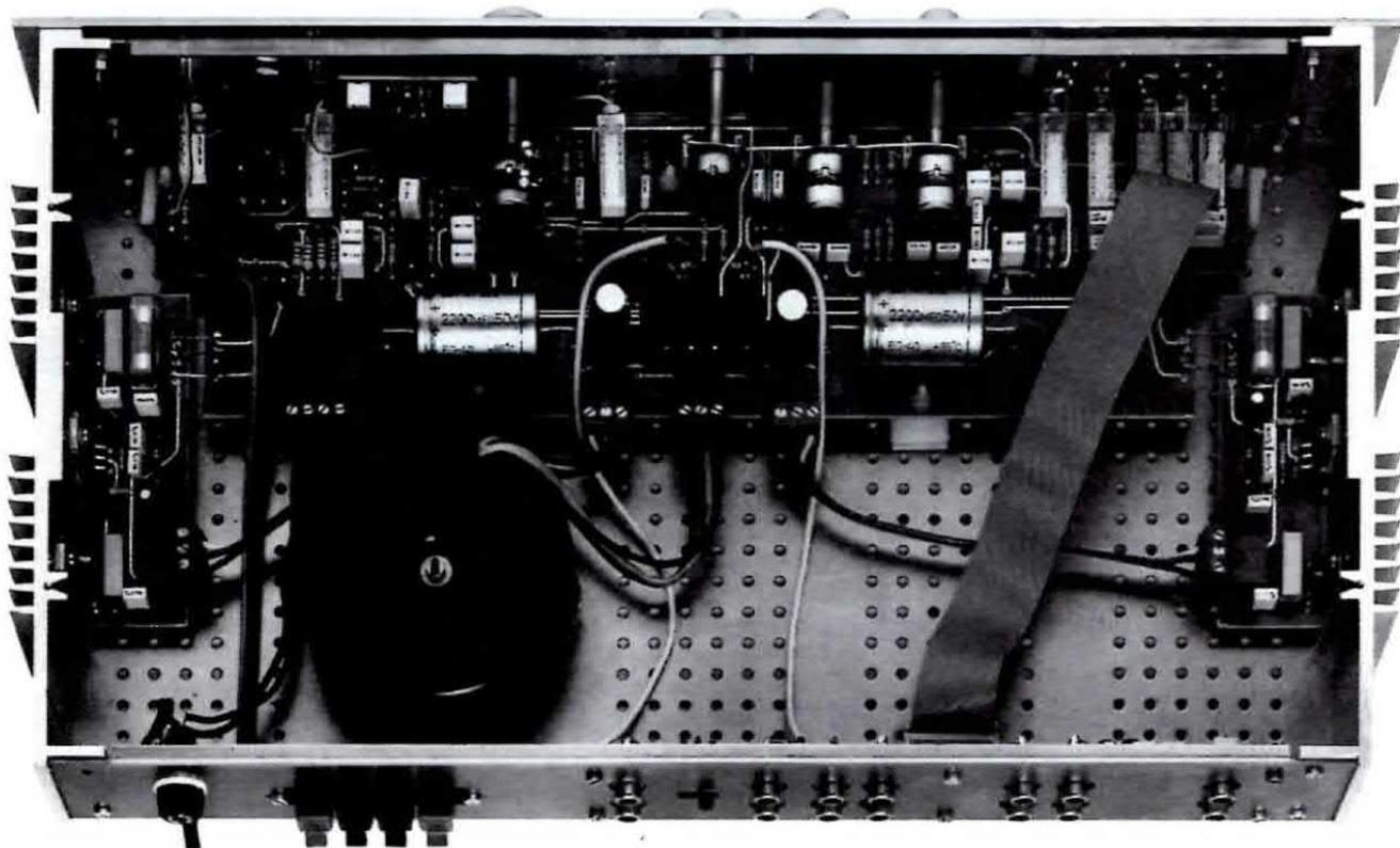
**Fig. 2** Come vedesi in questa foto, sulle due alette laterali del mobile andranno fissati i due stadi finali. Sul piano base applicherete il circuito LX.761 e sul pannello posteriore lo stadio d'ingresso LX.760 e le morsettiere di uscita per gli altoparlanti. Si noti a sinistra il trasformatore toroidale.
