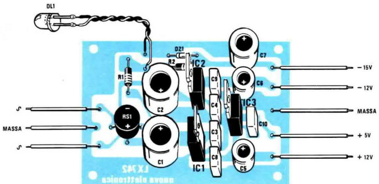
**Fig. 5** Schema pratico dello stadio di alimentazione. I tre fili riportati a sinistra andranno a collegarsi al secondario di T1, mentre i cinque riportati a destra andranno a collegarsi al circuito stampato base LX.740, visibile in fig. 6.
