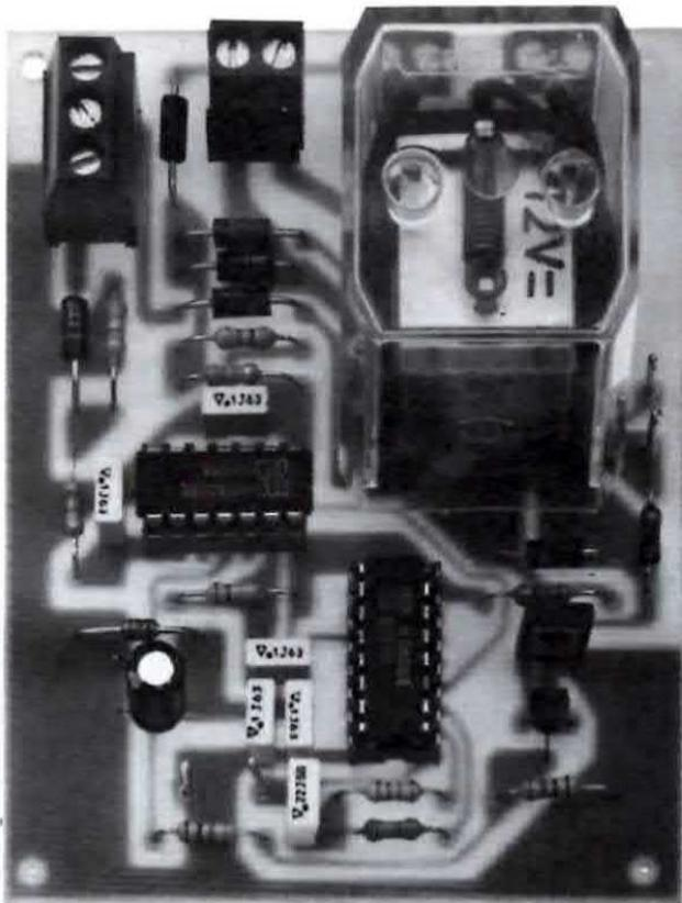
Questo impulso negativo, tramite C4, provvederà ad eccitare il Flip-Flop composto dai due nand IC1/C e IC1/D e, così facendo, convertirà la sua uscita (piedino 11) dalla condizione logica 0 alla condizione logica 1, vale a dire che su tale uscita avremo disponibile una tensione positiva che, tramite R8, raggiungerà la base del transistor TR1 collegato in darlington con TR2.
