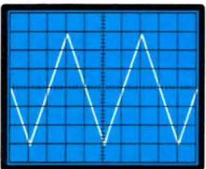
**Fig. 17** Centrata l'onda triangolare, avrete la matematica certezza che la semionda negativa avrà un'ampiezza massima di  $-5$  volt e la semionda positiva di  $+5$  volt positivi, sempre rispetto a massa.
