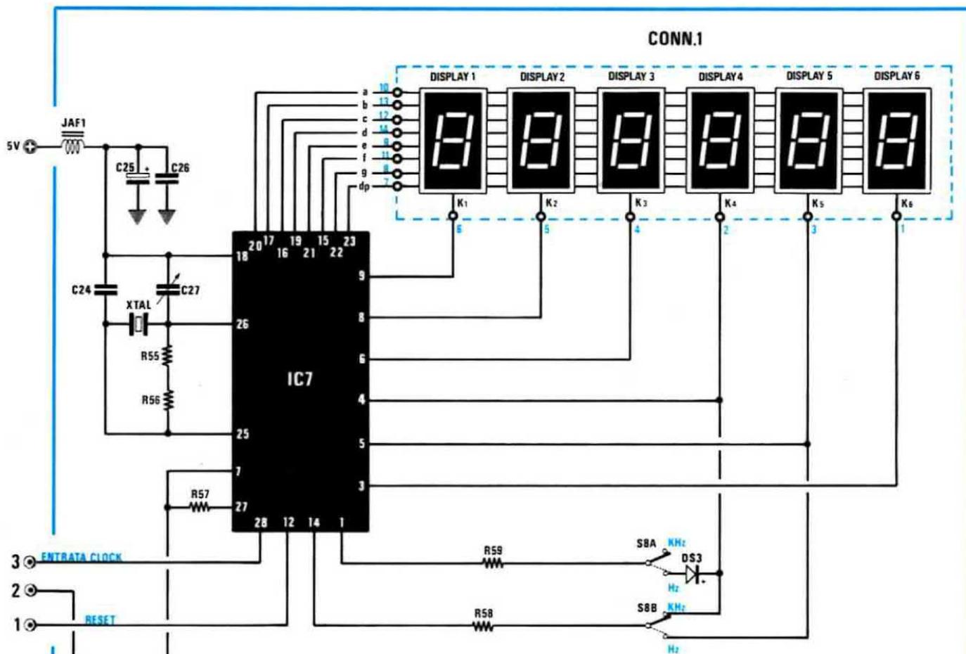
**Fig. 2** Applicando al nostro generatore di funzioni questo frequenzimetro digitale, avrete la possibilità di leggere esattamente la frequenza generata. Una piattina completa di connettori provvederà a collegare direttamente questo stadio al generatore. I valori dei componenti sono riportati nella pagina a fianco.
