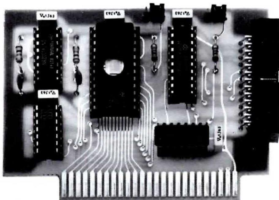
**Fig. 2** Foto della interfaccia come si presenterà a costruzione ultimata. La eprom con la "finestra" ancora scoperta visibile al centro, la riceverete programmata e "coperta" da una etichetta con sopra stampato EP.785.
