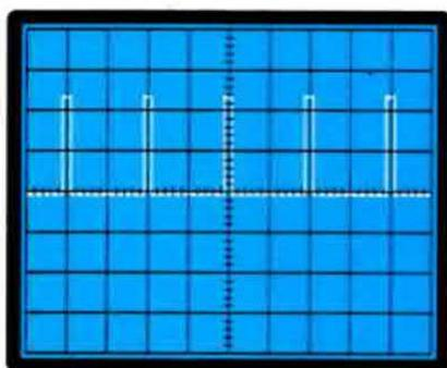
**Fig. 22** Pigiando il pulsante **S6**, le onde quadre, sempre prelevate sull'uscita TTL, si trasformeranno in impulsi e, come per le precedenti, la loro ampiezza massima risulterà di 5 volt rispetto alla massa.
