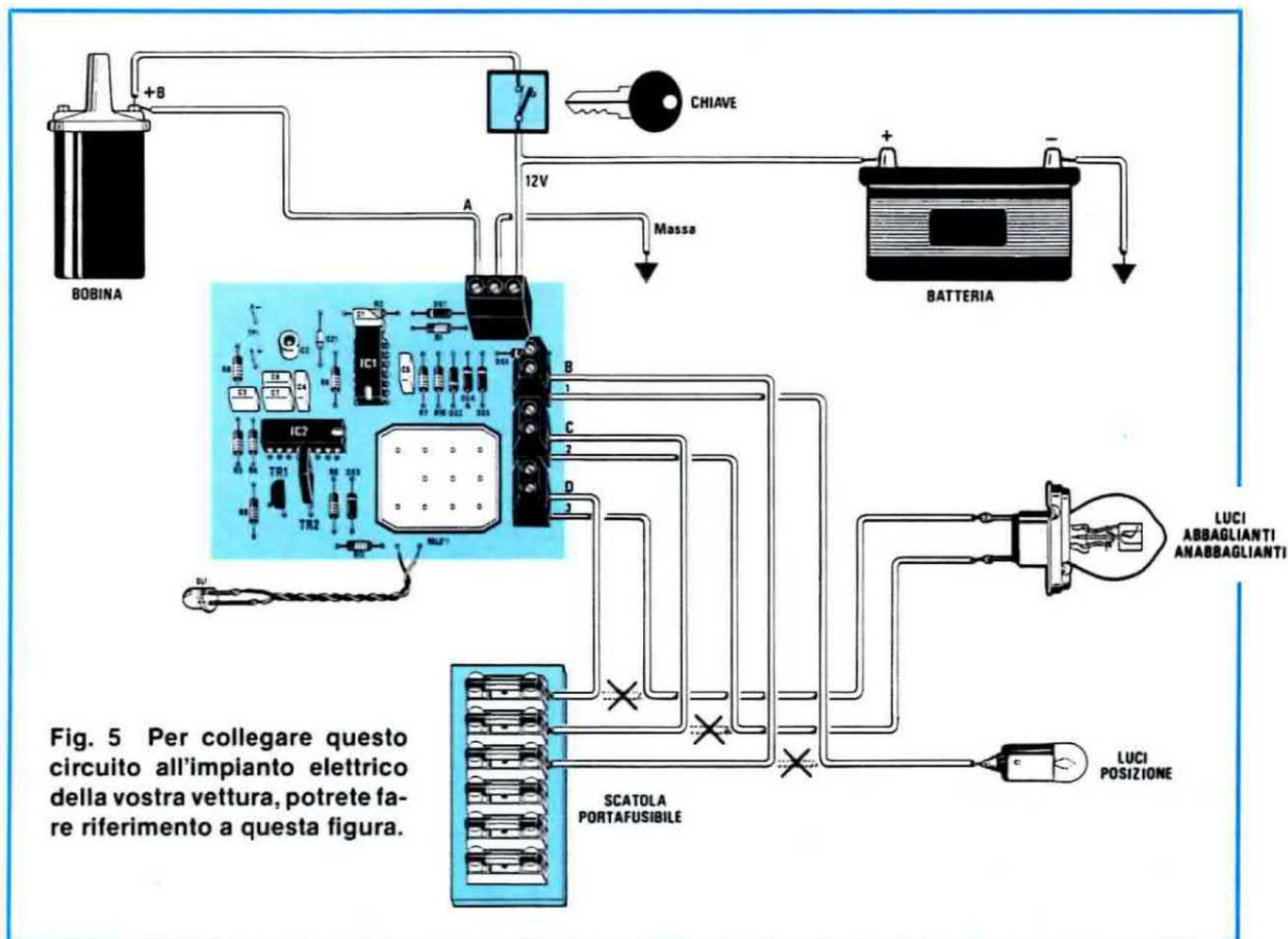
**Fig. 5** Per collegare questo circuito all'impianto elettrico della vostra vettura, potrete fare riferimento a questa figura.
