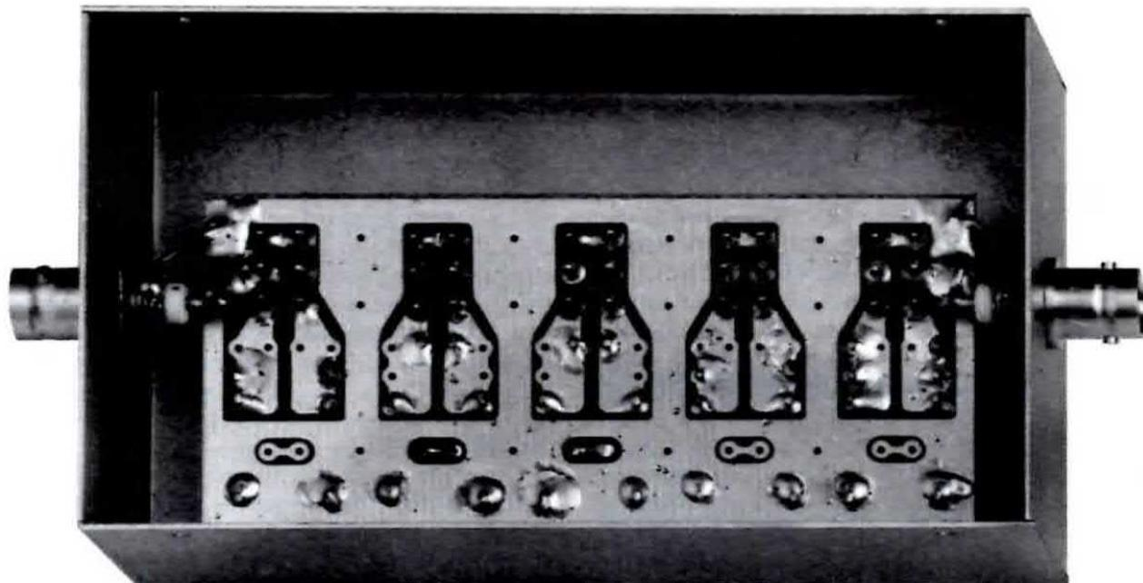
**Fig. 10** Il circuito stampato andrà collocato entro la scatola metallica da noi fornita. Dopo aver fissato sui due lati i BNC, ne salderete il terminale centrale e la carcassa di massa alle due piste laterali, come vedesi in questa foto.
