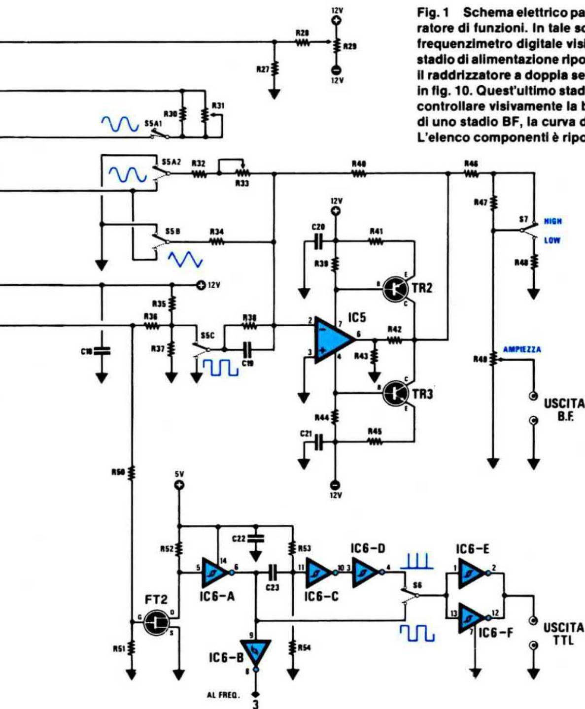
Fig. 1 Schema elettrico parziale del generatore di funzioni. In tale schema manca il frequenzimetro digitale visibile in fig. 2, lo stadio di alimentazione riportato in fig. 4 ed il raddrizzatore a doppia semionda visibile in fig. 10. Quest'ultimo stadio ci servirà per controllare visivamente la banda passante di uno stadio BF, la curva di un filtro, ecc. L'elenco componenti è riportato a pag. 47.
