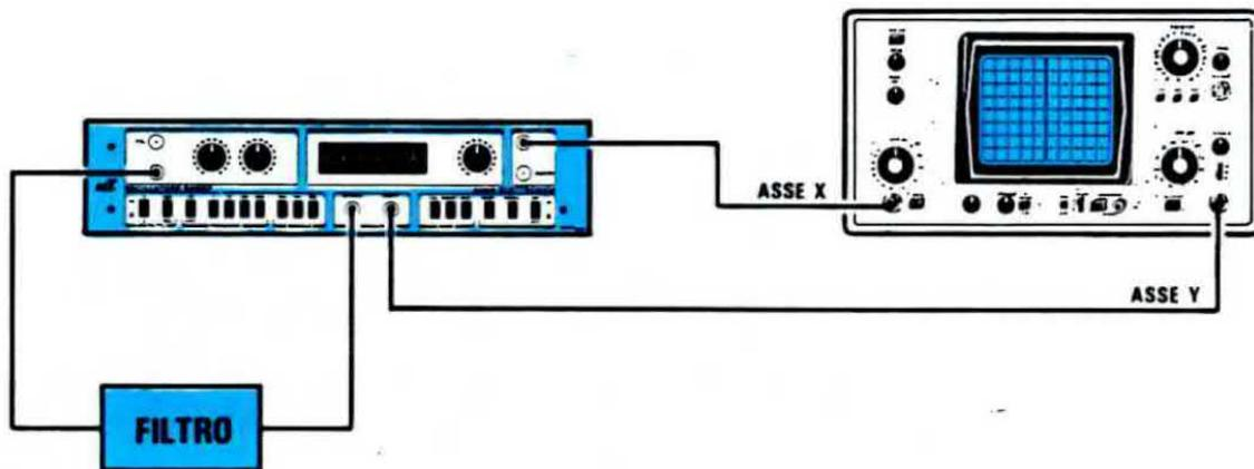
**Fig. 11** Per ottenere sullo schermo dell'oscilloscopio le fig. 12-13-14, si dovrà collegare l'ingresso dell'amplificatore o del filtro, all'USCITA BF del generatore, l'uscita dell'amplificatore o del filtro all'ENTRATA RADDRIZZ. Gli ingressi X e Y dell'oscilloscopio andranno collegati all'USCITA RADDRIZZ. e all'USCITA SWEEP, ponendo il generatore in SWEEP.
