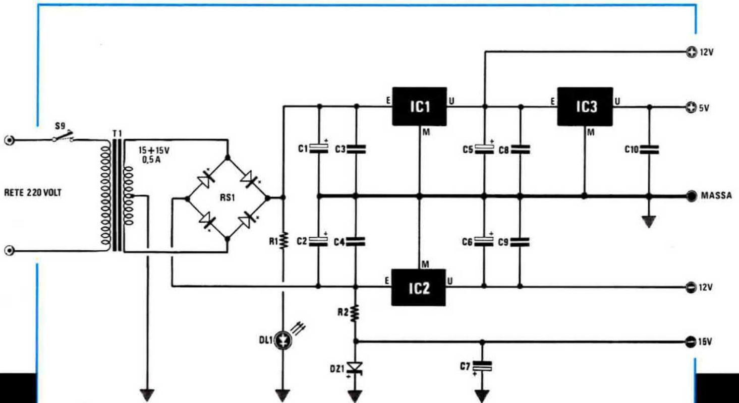
**Fig. 4** Schema elettrico completo dello stadio di alimentazione. Anche tutti i componenti di questo stadio, compreso il trasformatore T1, fanno parte di un kit separato siglato LX.742. L'elenco componenti è riportato nella pagina a fianco.
