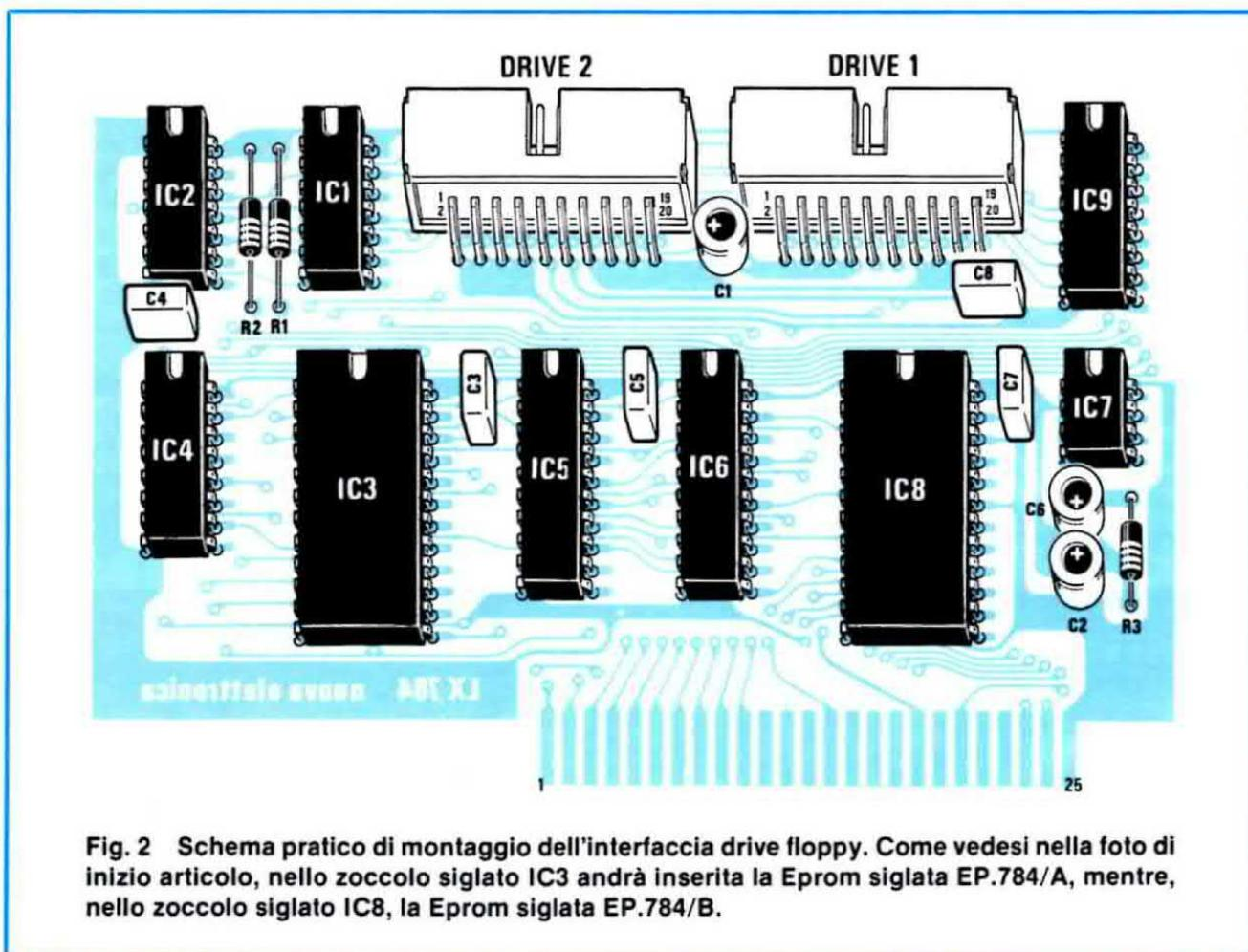
**Fig. 2** Schema pratico di montaggio dell'interfaccia drive floppy. Come vedesi nella foto di inizio articolo, nello zoccolo siglato IC3 andrà inserita la Eprom siglata EP.784/A, mentre, nello zoccolo siglato IC8, la Eprom siglata EP.784/B.
