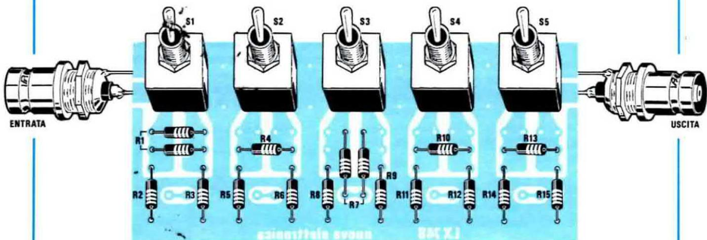
Fig. 9 Lo stesso circuito stampato potrà essere utilizzato anche per realizzare un attenuatore con impedenza costante di 75 ohm (come qui sopra riportato) o di 600 ohm. Sul circuito stampato sono presenti fori e piste per collegare facilmente più valori, in parallelo o in serie. Nella lista di fig. 1 troverete i valori richiesti per 50-75-600 ohm.
