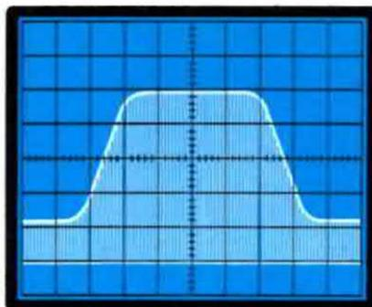
**Fig. 12** Con il raddrizzatore a doppia semionda potrete vedere sullo schermo dell'oscilloscopio la completa banda passante di un qualsiasi circuito BF. Nei prossimi numeri vi spiegheremo come leggere la frequenza.
