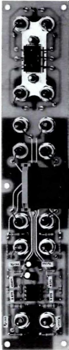
**Fig. 3** In questa foto si può notare come risultano disposti tutti i componenti sul circuito stampato base LX.761 e su quello d'ingresso LX.760 e come gli stessi vengono collegati tra di loro tramite una piallina cablata. Si noti in basso a destra il Vu-Meter a diodi led, già innestato sul connettore presente nel circuito base.
