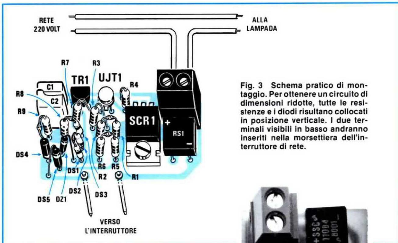
Fig. 3 Schema pratico di montaggio. Per ottenere un circuito di dimensioni ridotte, tutte le resistenze e i diodi risultano collocati in posizione verticale. I due terminali visibili in basso andranno inseriti nella morsettiera dell'interruttore di rete.
