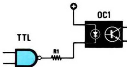
**Fig. 6** Solo collegando l'anodo del diodo alla tensione positiva dei 5 volt e il catodo all'uscita del TTL, si riuscirà a far scorrere nel diodo la corrente richiesta. Per il valore di R1 leggere l'articolo.
