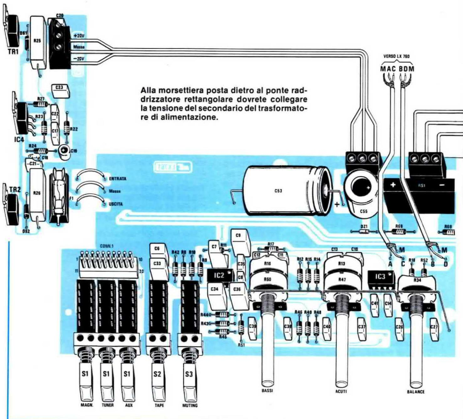
Alla morsetteria posta dietro al ponte raddrizzatore rettangolare dovrete collegare la tensione del secondario del trasformatore di alimentazione.
