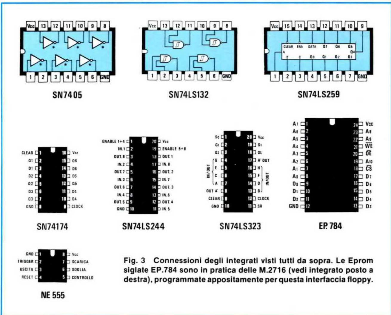
Fig. 3 Connessioni degli integrati visti tutti da sopra. Le Eprom siglate EP.784 sono in pratica delle M.2716 (vedi integrato posto a destra), programmate appositamente per questa interfaccia floppy.
