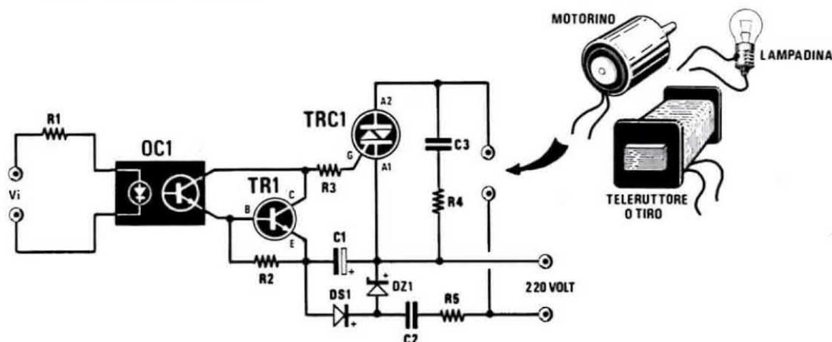
Fig. 15 Per eccitare telerruttori, accendere lampade o alimentare motorini con tensione di rete a 220 volt, dovreste utilizzare necessariamente un diodo triac ed aggiungere un circuito di alimentazione per TR1.
