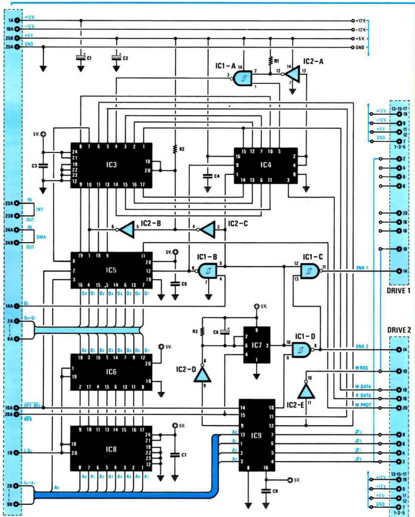
Fig. 1 Schema elettrico dell'interfaccia drive floppy. La fascia verticale visibile a sinistra rappresenta il connettore a pettine, le due fasce poste a destra i due connettori di uscita per i drive. Precisiamo che i terminali di questi due connettori (esclusi i piedini 14) sono tutti collegati in parallelo, anche se per non complicare il disegno abbiamo evidenziato in colore il solo collegamento dei piedini 2 e 10.
