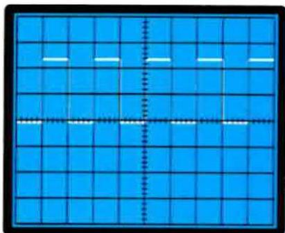
**Fig. 21** Pigiando il pulsante **ON-DE QUADRE**, sullo schermo le semionde negative e positive avranno un'ampiezza massima di 10 volt, mentre quelle che preleverete dall'uscita TTL, un'ampiezza massima di 5 volt.
