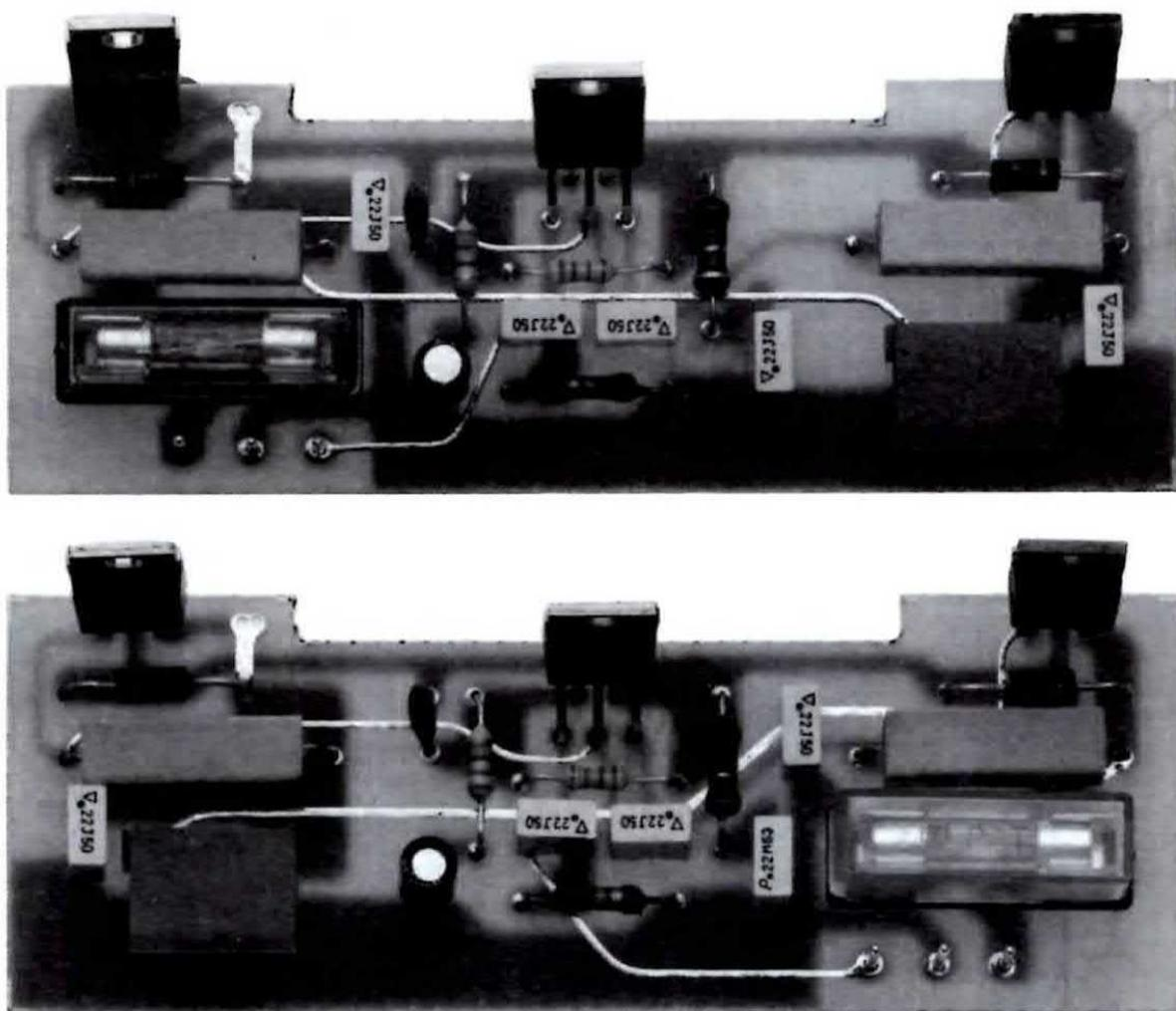
**Fig. 11** Foto dei due circuiti degli stadi finali con i fusibili collocati uno a destra e l'altro a sinistra. Si consiglia di tenere leggermente distanziate le due resistenze a filo dal circuito stampato, per permettere al loro corpo di disperdere meglio il calore generato.
