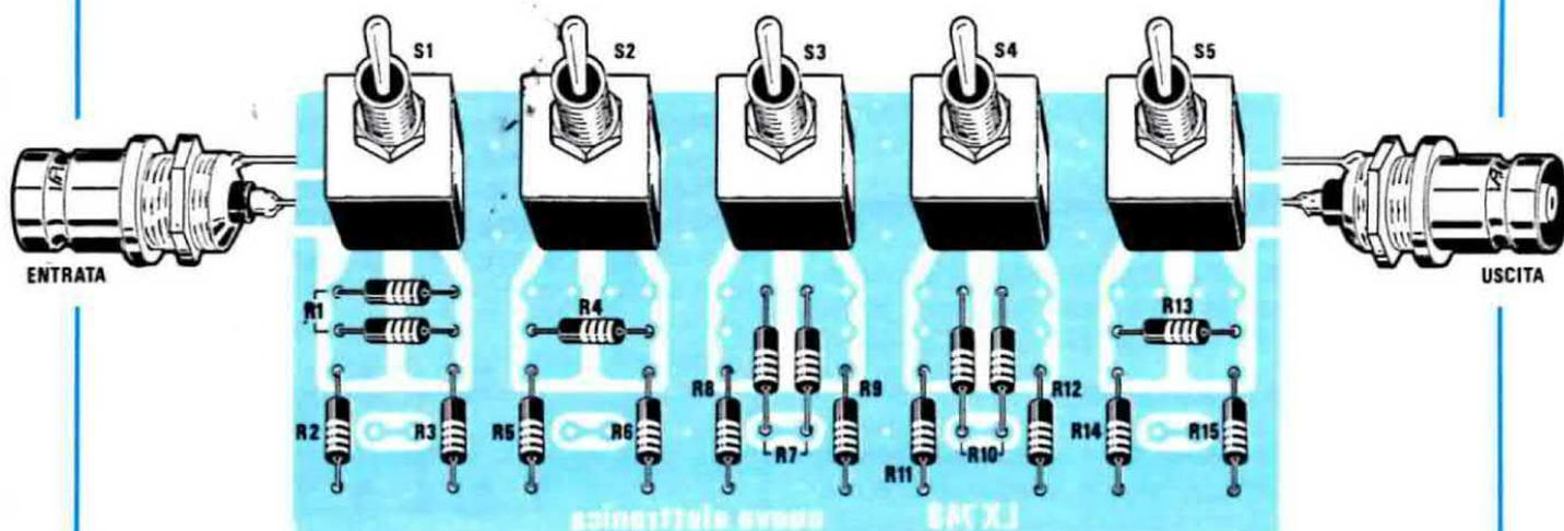
Fig. 8 Schema pratico di montaggio di un attenuatore con impedenza costante di 50 ohm. Per ottenere per R1 un valore di 6 ohm, dovrete inserire in parallelo due resistenze da 12 ohm, mentre per R7, da 24 ohm, ne dovrete collegare in serie due da 12 ohm e per R10, da 54 ohm, due in serie da 27 ohm, condizione che si otterrà collegando tali resistenze in verticale, come vedesi in disegno.
