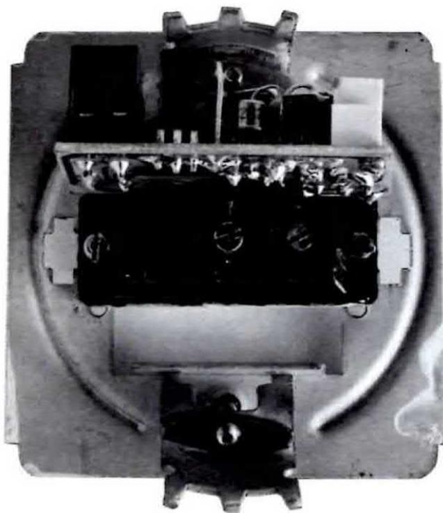
**Fig. 6** I due terminali che fuoriescono dal circuito stampato sono stati posizionati ad una distanza tale, da poter collimare esattamente con la morsettiera presente su qualsiasi tipo di interruttore di rete.
