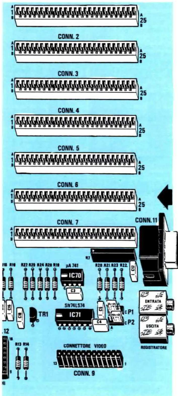
**Fig. 4** Questa interfaccia andrà inserita nel CONN.6, rivolgendo gli integrati siglati IC9 - IC7 (vedi schema pratico di fig. 2) verso la "freccia" e gli integrati IC2 - IC4 verso l'interno del computer.
