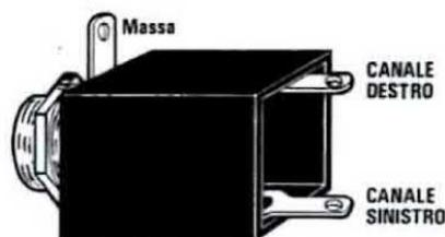
**Fig. 16** Dopo aver fissato la presa jack della cuffia sul contropannello del mobile, collegherete i tre terminali alle uscite "cuffia" presenti tra il commutatore S6 e S7, come visibile in fig. 9.
