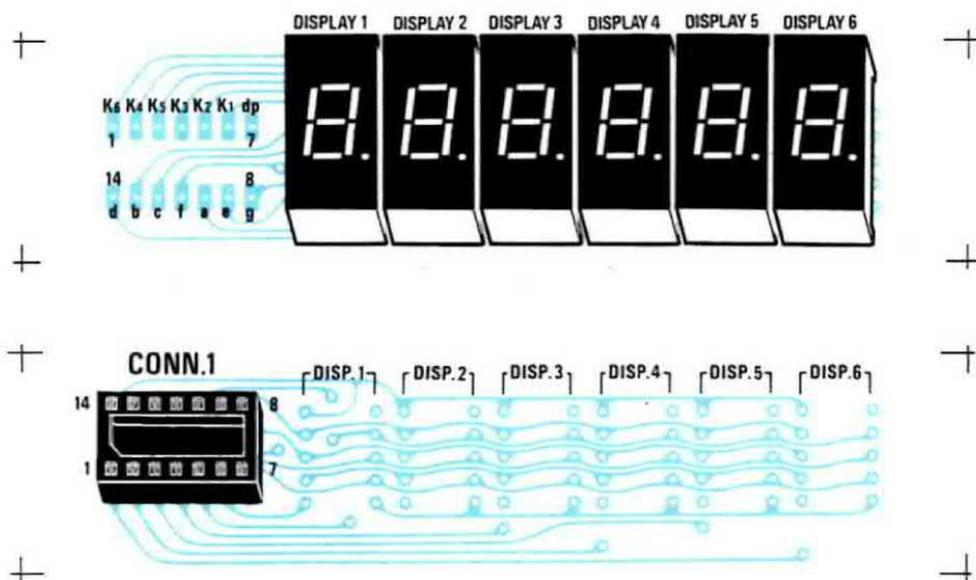
**Fig. 8** Schema pratico di montaggio dei display sul circuito a fori metallizzati siglato LX.741. Dal lato opposto in cui avrete inserito lo zoccolo per la piattina, dovrete inserire tutti i display con il punto decimale rivolto verso il basso.
