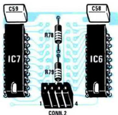
**Fig. 15** Sopra, lo schema pratico del Vu-Meter a diodi led visto dal lato integrati. Dal lato opposto di tale circuito monterete le due colonne di diodi led piatti come visibile in fig. 8. Come evidenziato nella foto posta qui in basso, questo circuito andrà innestato sul connettore che avrete già applicato sul circuito base LX.761.
