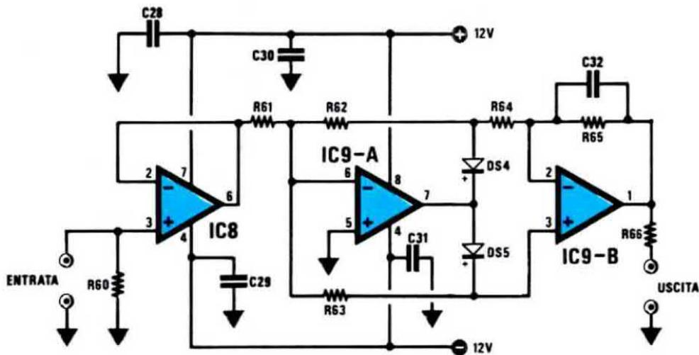
**Fig. 10** Schema elettrico del "raddrizzatore a doppia semionda" necessario per visualizzare sullo schermo dell'oscilloscopio la banda passante di qualsiasi stadio di BF, la curva di risposta di un filtro, ecc. Questo stadio viene montato sul circuito base LX.740 (vedi IC8 e IC9 in prossimità dei due BNC centrali di fig. 6). Per i valori dei componenti vedere a pag.47.
