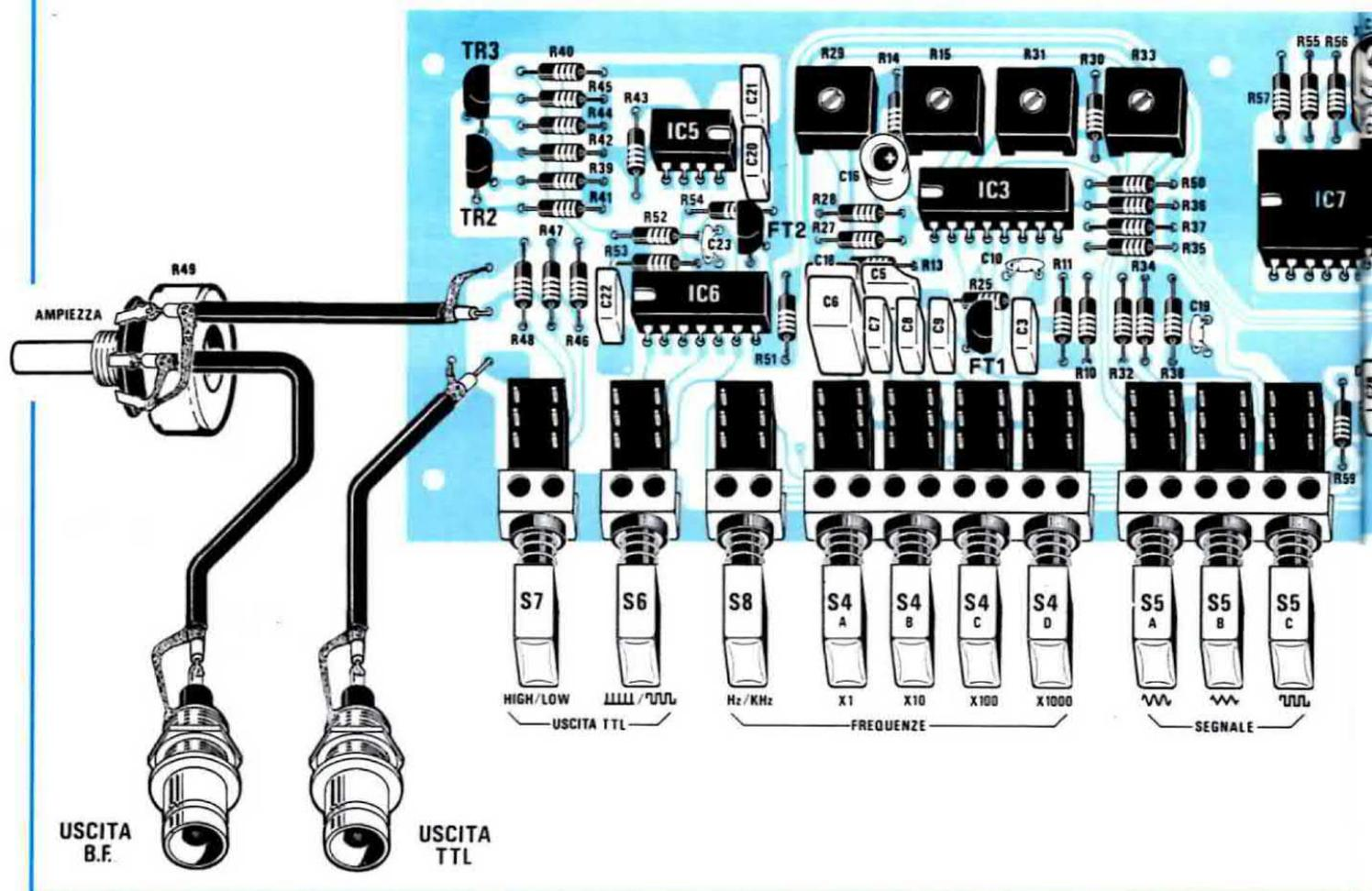
componenti nelle posizioni richieste, saldandoli accuratamente e usando l'accortezza, se il terminale di un componente (ad esempio un compensatore o un trimmer) non dovesse entrare nel relativo foro, di non allargare quest'ultimo con la punta di un trapano (così facendo, asportereste dal foro anche lo strato metallico di collegamento), ma di limare invece il terminale.
