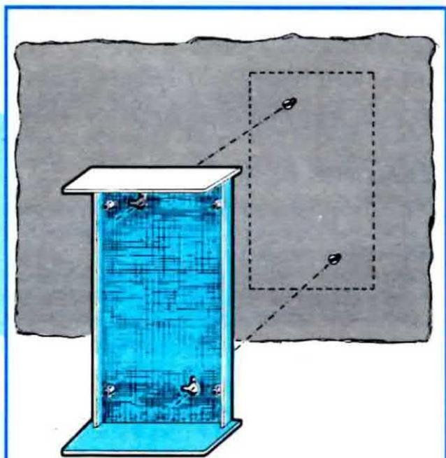
**Fig. 12** Per fissare la sonda alla parete, potrete inserire nel muro due tasselli e utilizzare i due fori già presenti nel retro del mobile. Per evitare cortocircuiti, verificate che le teste delle due viti di fissaggio non entrino in contatto con le piste del circuito stampato.
