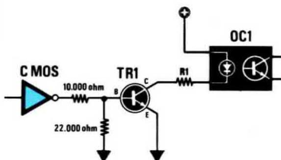
**Fig. 8** Per pilotare un diodo emittente con un C/Mos è possibile scegliere questo secondo schema. Per la polarizzazione di base si utilizzeranno i valori indicati, mentre si dovrà calcolare il valore della R1.
