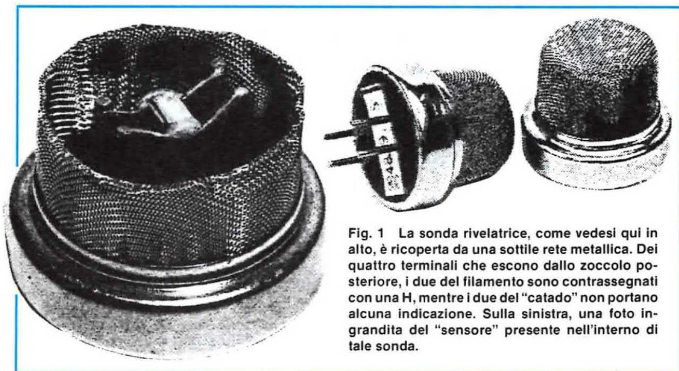
Fig. 1 La sonda rivelatrice, come vedesi qui in alto, è ricoperta da una sottile rete metallica. Dei quattro terminali che escono dallo zoccolo posteriore, i due del filamento sono contrassegnati con una H, mentre i due del "catodo" non portano alcuna indicazione. Sulla sinistra, una foto ingrandita del "sensore" presente nell'interno di tale sonda.
