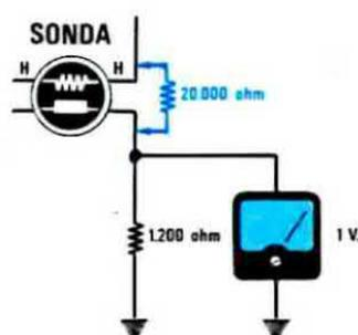
**Fig. 3** Appena si verificherà una piccola fuga di gas, la resistenza filamento-catodo da 150.000 ohm scenderà bruscamente a 20.000 ohm, quindi ai capi della resistenza da 1.200 ohm la tensione raggiungerà il valore di circa 1 volt.
