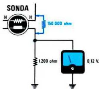
**Fig. 2** Se nella stanza non è presente nessun vapore velenoso, tra il filamento ed il catodo esisterà una resistenza ohmica di circa 150.000 ohm, quindi ai capi della resistenza da 1.200 ohm sarà presente una tensione di circa 0,12 volt.
