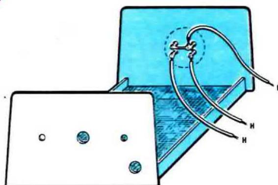
Fig. 8 Su di una parete laterale del mobile plastico effettuerete tre fori per la capsula piezoelettrica ed uno per il filo di rete a 220 volt, mentre, su quella opposta, i quattro fori necessari per i terminali della sonda rivelatrice.
