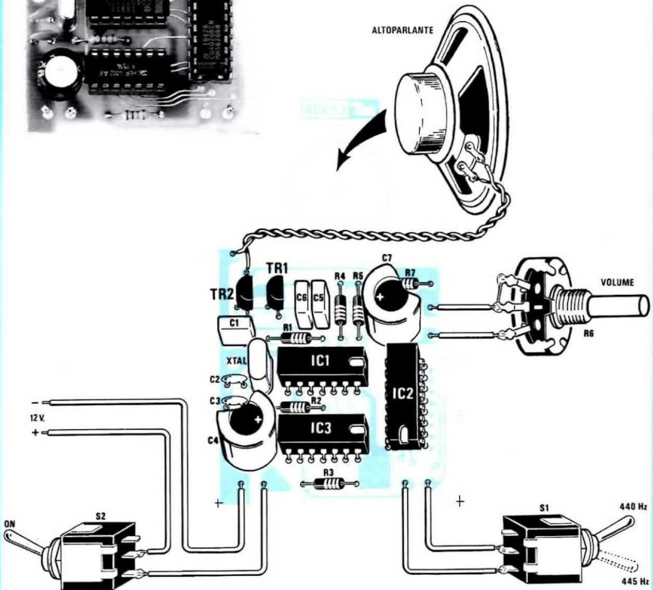
te, verrà utilizzato come potenziometro per dosare l'intensità della nota di uscita.
