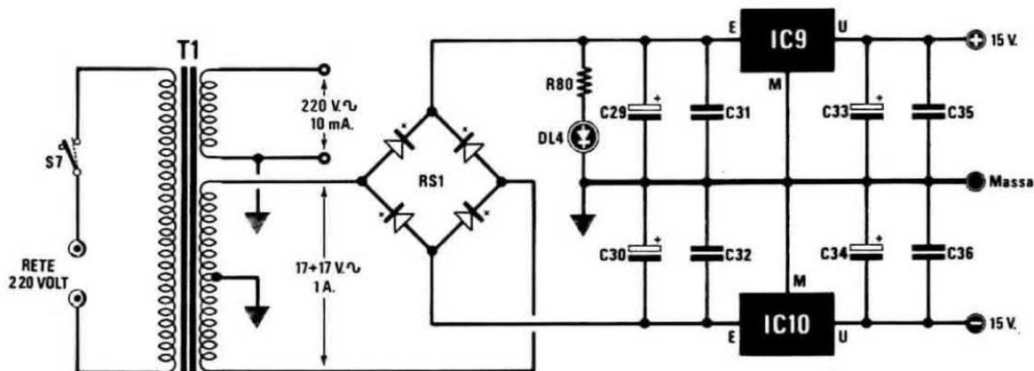
**Fig. 6** Schema elettrico dello stadio alimentatore che trova posto nello stesso circuito stampato del tracciacurve. I valori dei componenti sono riportati nella pagina di destra.
