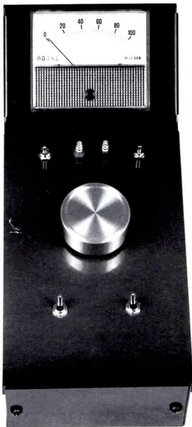
**Fig. 6** Una sola manopola ci permetterà di regolare la sensibilità e la discriminazione. I deviatori presenti servono solo per modificare la potenza del suono, la frequenza della nota e per spegnere il circuito. In alto, sotto allo strumento, sono visibili i terminali prova pila.
