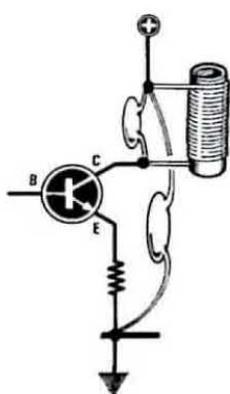
**Fig. 2** Sul punto di congiunzione della bobina di sintonia con il condensatore di accordo, occorre sempre collegare un condensatore di "fuga", con l'altra estremità collegata al punto di massa dell'emettitore del transistor. Se tale condensatore verrà collegato a una certa distanza (vedi a destra), il transistor potrebbe non oscillare.
