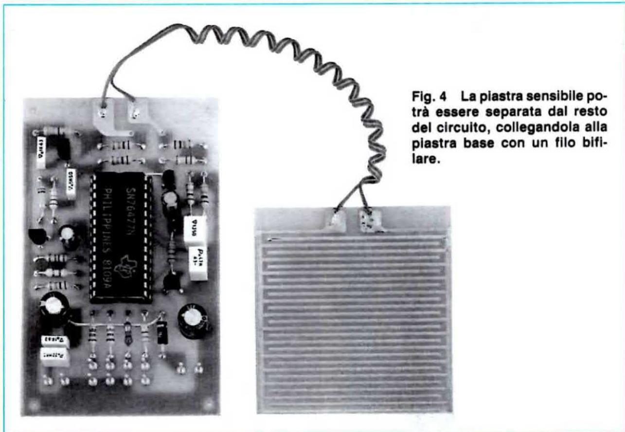
**Fig. 4** La piastra sensibile potrà essere separata dal resto del circuito, collegandola alla piastra base con un filo bifilare.
