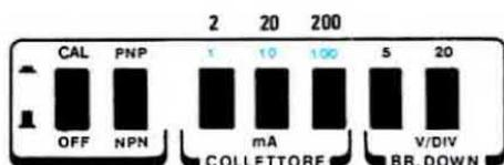
**Fig. 19** Posizionando questa stessa manopola nella posizione 0,2 volt  $\times$  divisione, dovremo raddoppiare la corrente indicata sui tre commutatori visibili in figura.
