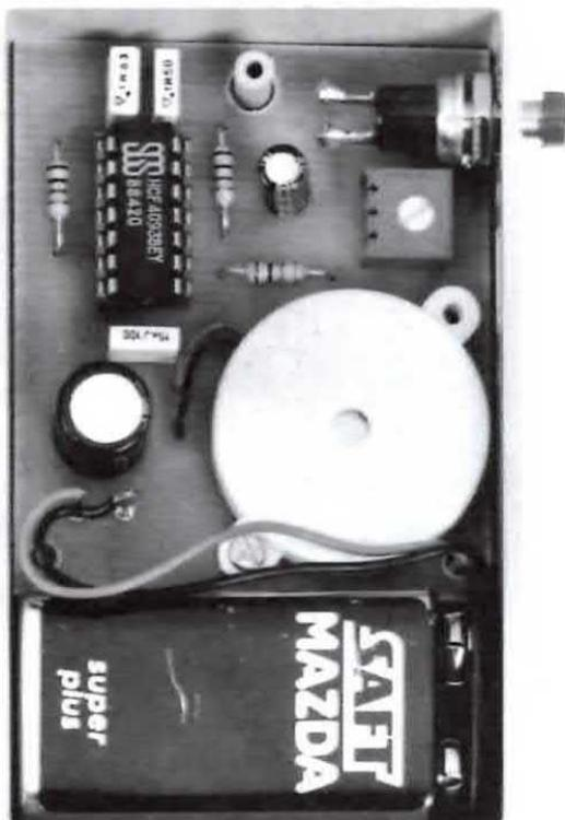
La pila di alimentazione trova posto nel vano presente in basso sotto alla capsula piezoelettrica.
