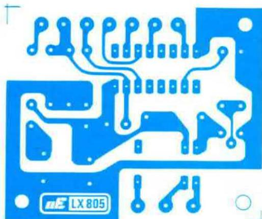
Fig. 4 Disegno a grandezza naturale del circuito stampato LX.805 visto dal lato rame.
