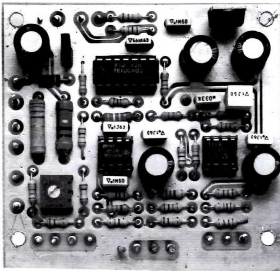
Fig. 15 Foto ingrandita del circuito LX.757. Per fissare questo circuito al mobile del cerca-metalli useremo i quattro distanziatori plastici autoadesivi presenti nel kit.
