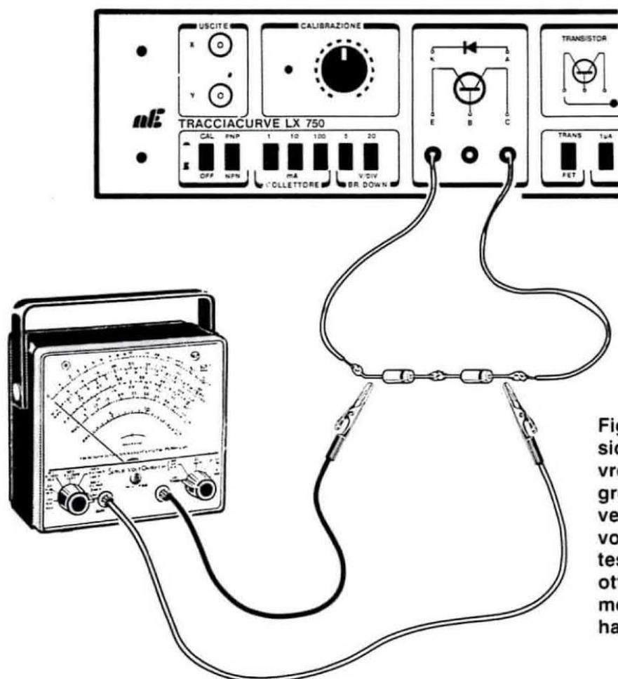
Fig. 29 Per tarare la tensione di «Breakdown» dovremo collegare agli ingressi E - C del tracciacurve due diodi zener da 15 volt, controllando con un tester il valore di tensione ottenuto. Non va infatti dimenticato che i diodi zener hanno una tolleranza.
