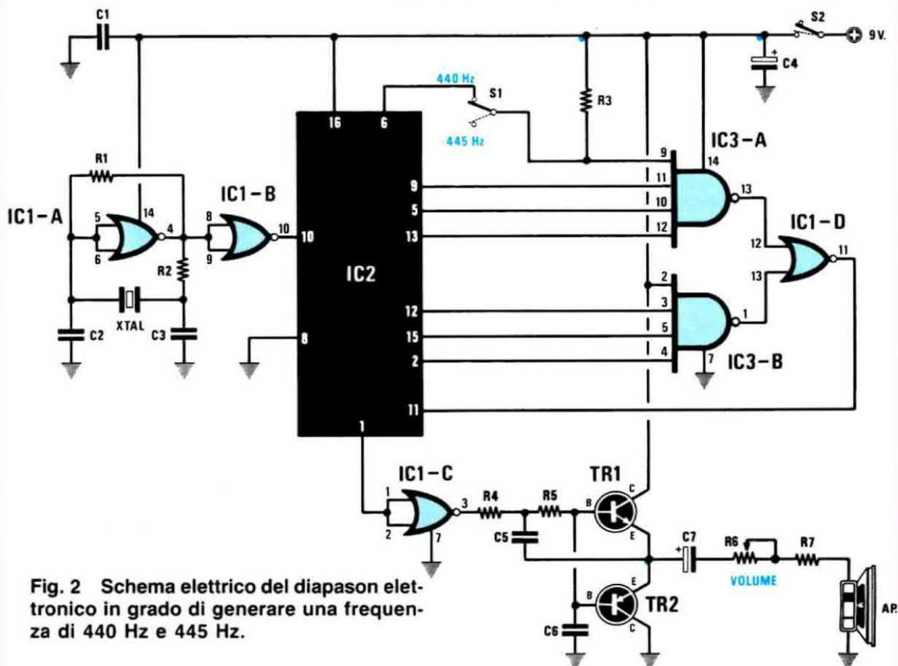
Fig. 2 Schema elettrico del diapason elettronico in grado di generare una frequenza di 440 Hz e 445 Hz.
