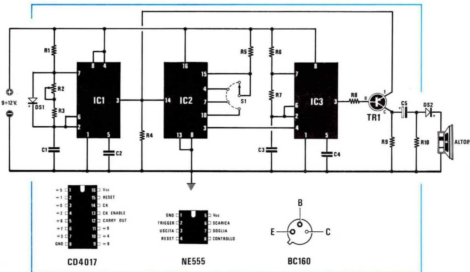
Per ottenere una tonalità differente in corrispondenza dei «tempi forti», sono necessari i due integrati, indicati nello schema elettrico con le sigle IC2 e IC3.
