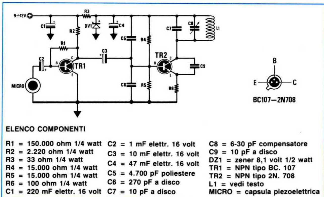
al collettore del transistor TR2, tramite un condensatore da 1 - 1,5 pF, uno spezzone di normale filo isolato in plastica di lunghezza compresa tra i 60 e gli 80 centimetri.
