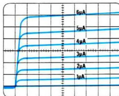
**Fig. 39** Premendo il pulsante «1 microamper corrente di base», ogni traccia che apparirà sullo schermo dell'oscilloscopio avrà un incremento di 1 microamper, come vedesi nella figura qui sopra riportata.
