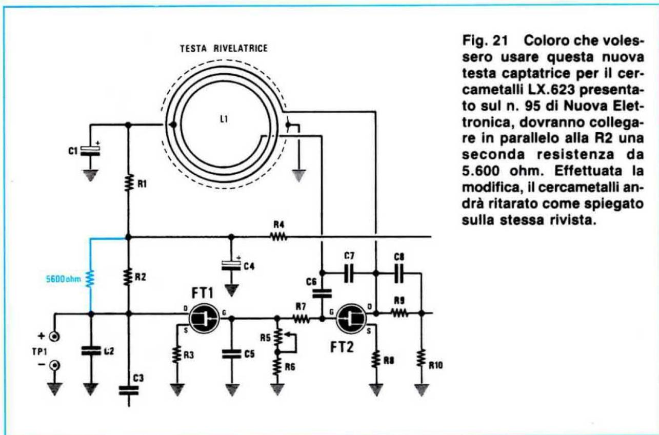
Fig. 21 Coloro che volessero usare questa nuova testa captatrice per il cercametalli LX.623 presentato sul n. 95 di Nuova Elettronica, dovranno collegare in parallelo alla R2 una seconda resistenza da 5.600 ohm. Effettuata la modifica, il cercametalli andrà ritarato come spiegato sulla stessa rivista.
