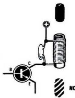
Pertanto, potrete utilizzare a tale scopo qualsiasi transistor NPN al silicio di bassa potenza e, volendo, anche di bassa frequenza, come il BC108 o il BC237.
