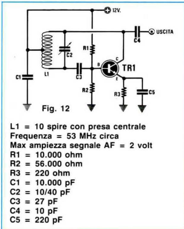
Anche se in questo schema abbiamo utilizzato una bobina con sole 10 spire provvista di presa centrale, nulla ci vieta, per scendere in frequenza, di utilizzare bobine con un maggior numero di spire oppure inferiore a 10 se desideriamo raggiungere i 100 MHz.
