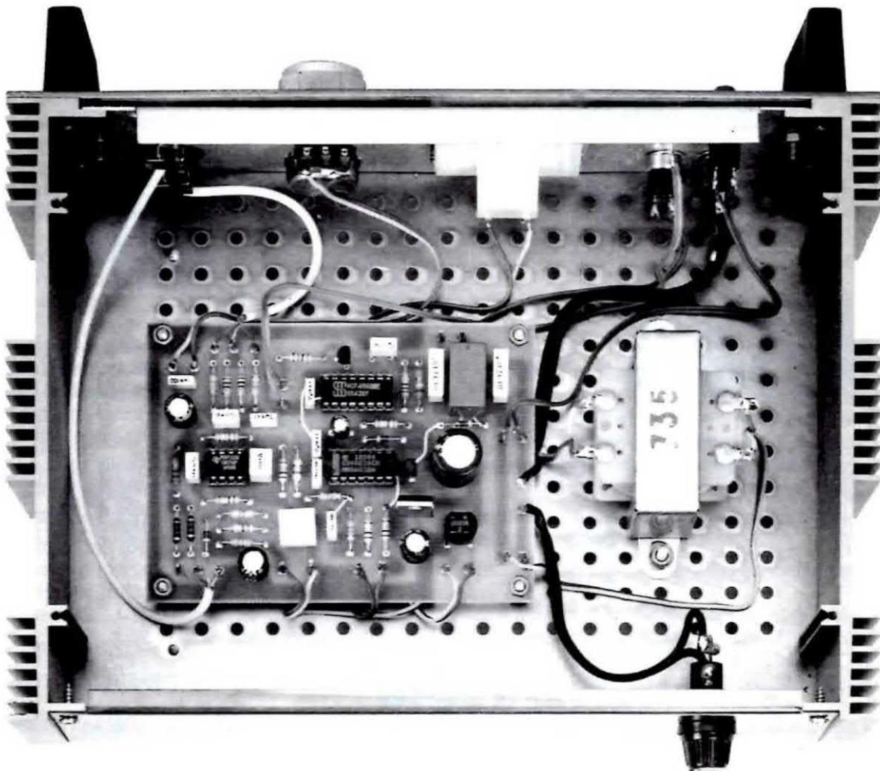
**Fig. 11** Sul piano del mobile andrà fissato il circuito stampato e il trasformatore di alimentazione (numero 735 o TN01.12), sul pannello posteriore il fusibile e le due uscite del relé (non visibili, perché il mobile riprodotto è un prototipo) e sul pannello anteriore, strumento, potenziometro, pulsante e prese jack.
