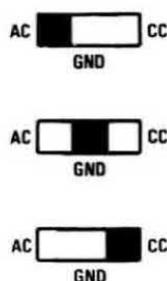
Fig. 21 Quando userete questo tracciacurve ricordatevi di porre sempre il comando AC - GND - CC in posizione CC. In molti oscilloscopi il CC è indicato DC.
