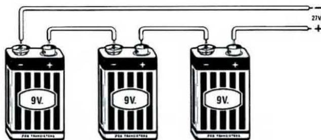
**Fig. 19** Nel collegare in serie le tre pile da 9 volt fate attenzione alla polarità. Il positivo della prima pila andrà a collegarsi al negativo della seconda pila ed il positivo della seconda al negativo della terza.
