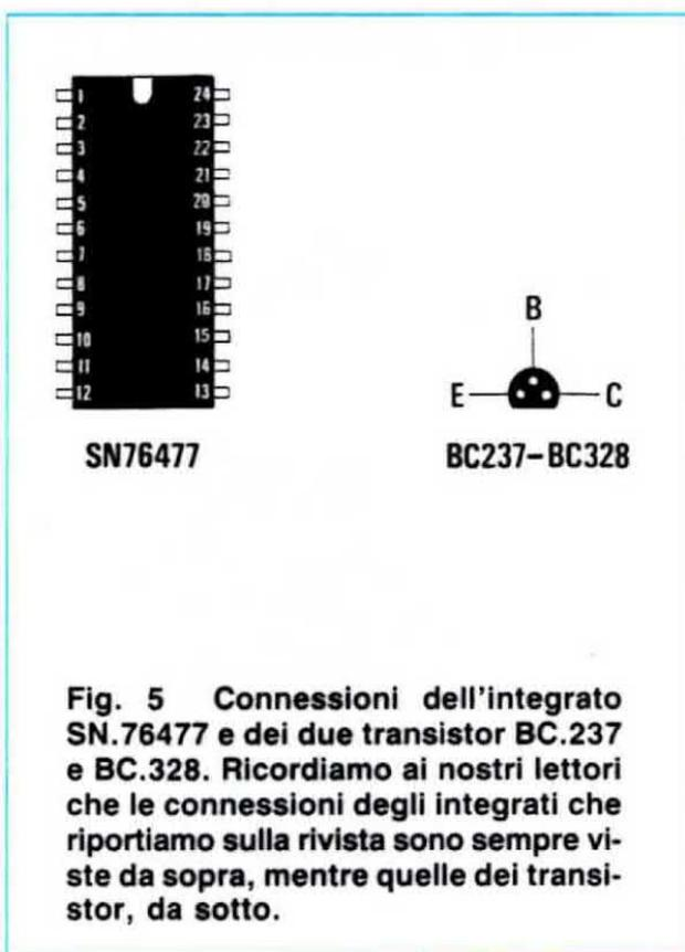
**Fig. 5** Connessioni dell'integrato SN.76477 e dei due transistor BC.237 e BC.328. Ricordiamo ai nostri lettori che le connessioni degli integrati che riportiamo sulla rivista sono sempre viste da sopra, mentre quelle dei transistor, da sotto.
