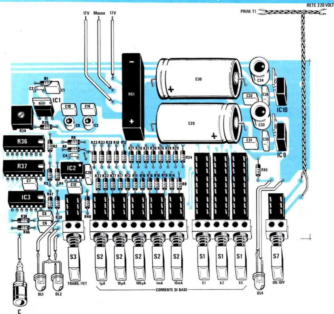
Fig. 14 Schema pratico di montaggio del tracciacurve. Come vedesi nella foto qui di lato, sui due integrati IC5 e IC1 dovremo applicare due piccole alette di raffreddamento. Anche se per ovvi motivi il disegno è stato spezzato al centro, nel montare questo circuito non incontrerete alcuna difficoltà, perché sul circuito stampato troverete un completo disegno serigrafico con tutte le sigle dei componenti. Si notino le due resistenze a filo R66 e R67 collocate in posizione verticale.
