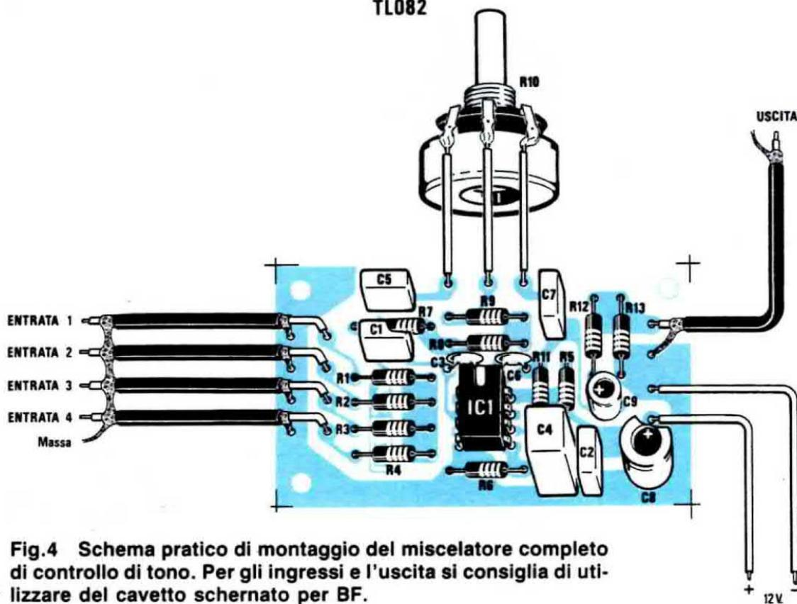
Fig.4 Schema pratico di montaggio del miscelatore completo di controllo di tono. Per gli ingressi e l'uscita si consiglia di utilizzare del cavetto schermato per BF.
