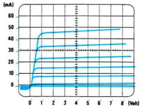
**Fig. 37** Premendo il pulsante «10 mA collettore», ogni quadretto in verticale corrisponderà ad un aumento di 10 milliamper. Questa portata si userà per transistor di media potenza, come potrebbe essere un 2N1711, un BD.137, ecc.
