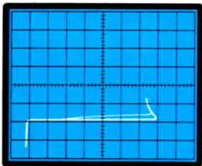
**Fig. 45** Per misurare la tensione di rottura del transistor, sarà sufficiente premere il pulsante **BR/DOWN X5** per i transistor con tensione di rottura inferiore a 50 volt e **X20** per i transistor con tensione di rottura inferiore a 200 volt.
