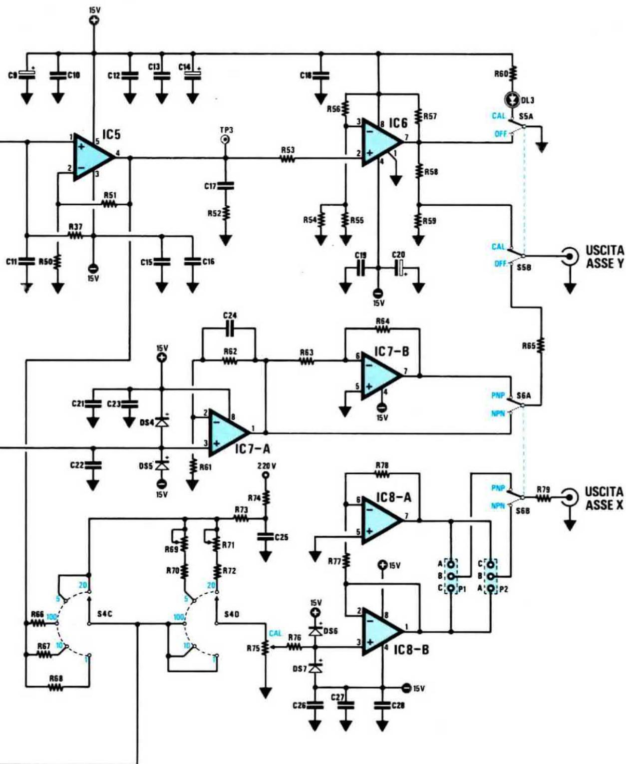
Fig. 5 Schema elettrico completo del tracciacurve, escluso il solo stadio alimentare visibile in fig. 6. I commutatori, che per ragioni di comprensibilità abbiamo disegnato del tipo rotativo, sono in pratica del tipo a pulsantiera.
