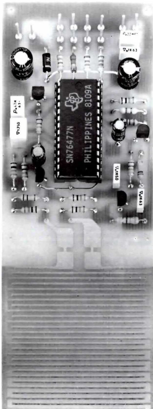
positiva), ma non appena TR1 si porterà in conduzione, sul collettore di TR3 avremo un impulso a livello logico 1 (presenza di tensione positiva), che metterà in funzione l'integrato IC1.
