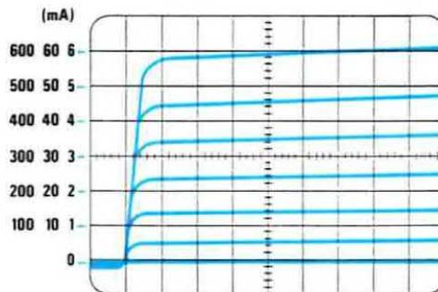
**Fig. 18** Ruotando la manopola dell'oscilloscopio nella posizione 0,1 volt  $\times$  divisione, sulla scala verticale avremo per quadretto la stessa corrente riportata sui commutatori.
