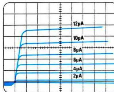
**Fig. 40** L'incremento di 1 microamper per ogni traccia (vedi fig. 39), è valido se sul pannello frontale viene premuto il pulsante «x1», se invece viene premuto il pulsante «x2», ogni traccia si incrementerà di 2 microamper come vedesi qui sopra.
