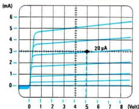
**Fig. 46** Per conoscere il «guadagno» di un transistor si prende un valore centrale di tensione di collettore (non importa se su 4 o 5 volt) e si congiunge alla quarta curva. Controllando a quale valore di corrente di collettore essa corrisponde si procederà come spiegato nell'articolo.
