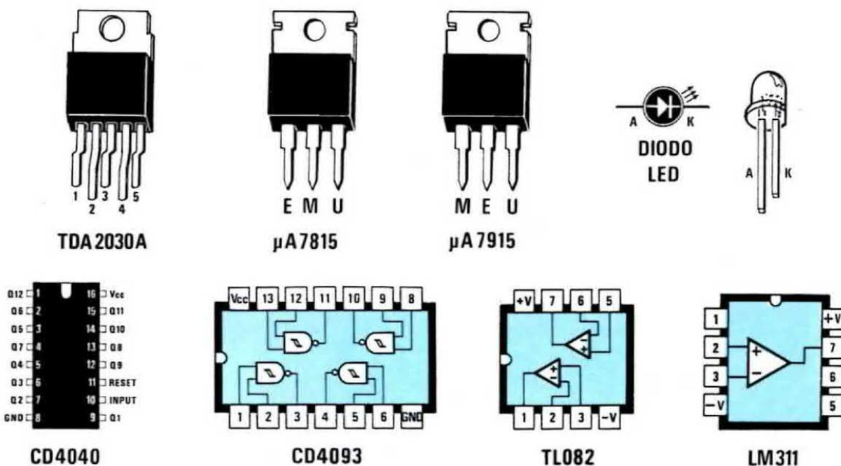
**Fig. 15** Connessioni dell'integrato TDA.2030 e dei due stabilizzatori uA.7815 e uA.7915 e dei rimanenti dual-line visti da sopra. Si noti sul diodo led la differente lunghezza dei due terminali anodo e catodo.
