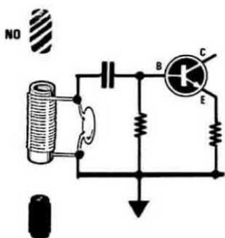
**Fig. 3** Il nucleo ferromagnetico presente all'interno della bobina di sintonia va sempre inserito nel "lato freddo"; se la bobina presenta un capo a massa, lo inseriremo come indicato a sinistra, se invece è collegata al positivo, lo inseriremo come vedesi nella figura di destra.
