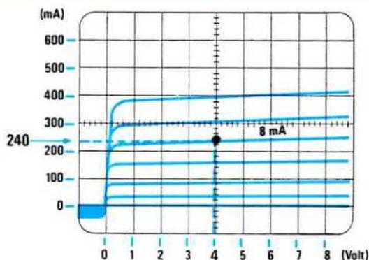
**Fig. 47** Prendendo come riferimento 4 volt di collettore, il transistor assorbe circa 240 mA con una corrente di Base (4 curva) di 8 mA e pertanto avremo un guadagno pari a  $240 : 8 = 30$  volte. Il guadagno non varia se prenderemo una diversa corrente di collettore.
