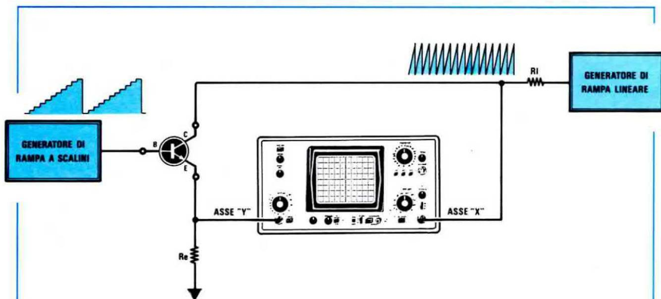
**Fig. 2** Per ottenere sullo schermo di un oscilloscopio le curve caratteristiche di un qualsiasi transistor, occorre applicare sulla sua Base una rampa a gradino variabile in corrente e sul suo Collettore una rampa lineare variabile in tensione.
