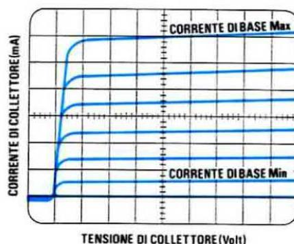
**Fig. 3** Come vedesi in questa figura, ogni quadretto in verticale corrisponde ad un valore di «corrente» che scorre sul Collettore, in funzione della corrente di Base. Ogni quadretto in orizzontale corrisponde invece alla «tensione» presente sul Collettore, ed infine le 6 tracce ci indicano la «corrente di Base» fornita dalla rampa a scalini.
