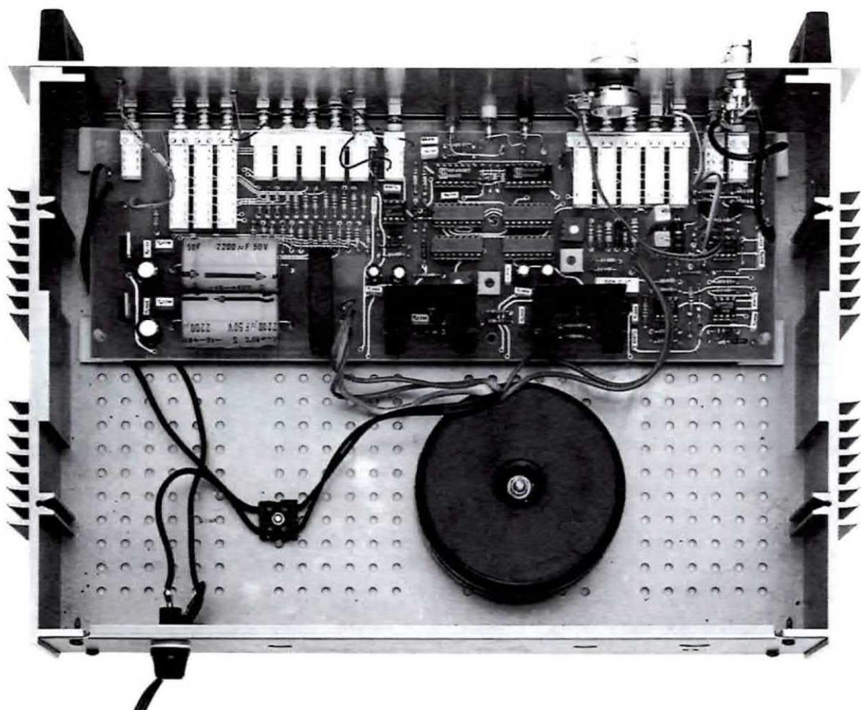
**Fig. 16** Il circuito stampato andrà fissato sul pannello base ad una giusta altezza dal piano, in modo da centrare le manopole dei commutatori nelle asole del pannello frontale. Si noti il trasformatore toroidale collocato subito dietro al circuito stampato.
