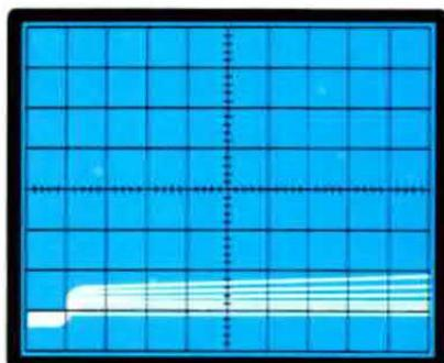
Fig. 9 Per ottenere curve caratteristiche molto precise sarebbe necessario tenere basso il valore della resistenza di Elettore (vedi fig. 2), ma così facendo, le 6 tracce che appariranno sullo schermo risulterebbero molto ravvicinate.
