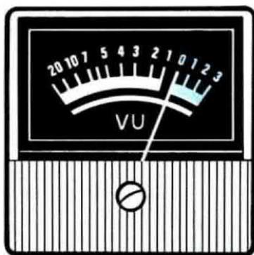
**Fig. 12** Riascoltando quanto avrete inciso sul nastro ad avvolgimento continuo, dovete ruotare il potenziometro della sublimazione in modo che l'ampiezza del segnale di BF porti la lancetta sullo 0 dB.
