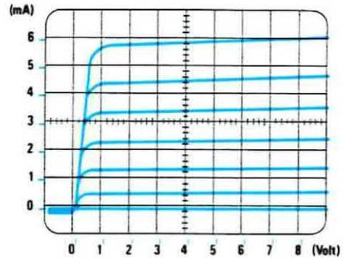
**Fig. 36** Premendo il pulsante «1mA collettore», ogni quadretto in verticale dell'oscilloscopio, partendo dallo 0, aumenterà di 1 milliamper. Questa portata si userà normalmente per transistor preamplificatori di piccola potenza.
