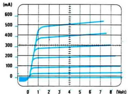
**Fig. 38** Premendo il pulsante «100 mA collettore», come è intuibile, ogni quadretto in verticale corrisponderà ad un aumento di 100 milliamper. Questa portata si dovrà utilizzare solo per transistor di potenza e mai per quelli di piccola potenza.
