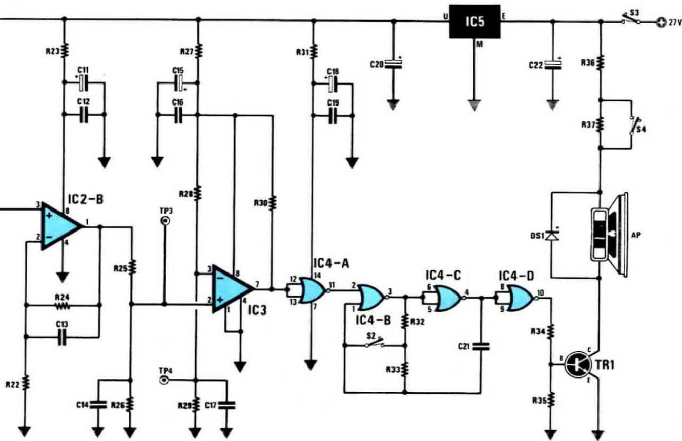
Fig. 5 Schema elettrico del cercametalli. Ruotando i due trimmer R4 e R5, sul test-point TP1 dovremo ottenere un segnale di 1 volt picco-picco (misurare con il solo oscilloscopio) o ancor meglio ritrovare su TP2 una tensione continua di 9,8 - 10 volt. Sui due test-point TP3 e TP4, quando il cercametalli risulta ben tarato, sarà presente una tensione di circa 1,8 volt. Avvicinando alla testa captatrice un qualsiasi oggetto metallico, la tensione su TP3 salirà bruscamente sui 9 - 10 volt.
