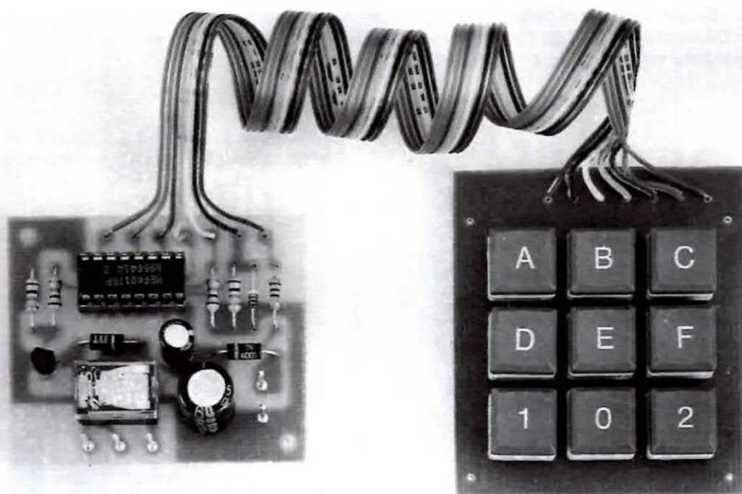
**Fig. 1** A sinistra, è visibile il circuito stampato LX.805 e a destra, il secondo circuito siglato LX.805/B, completo di 9 tasti di chiave. I cappucci di ogni tasto sono sfilabili e perciò potrete facilmente modificare la loro disposizione sulla tastiera.
