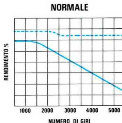
**Fig. 2** Il rendimento del motore di un'auto con una accensione tradizionale risulta ottimo solo a basso numero di giri, perchè, aumentando la velocità, la bobina non riesce più ad immagazzinare la necessaria energia induttiva, dato che le puntine rimangono chiuse per un tempo brevissimo.
