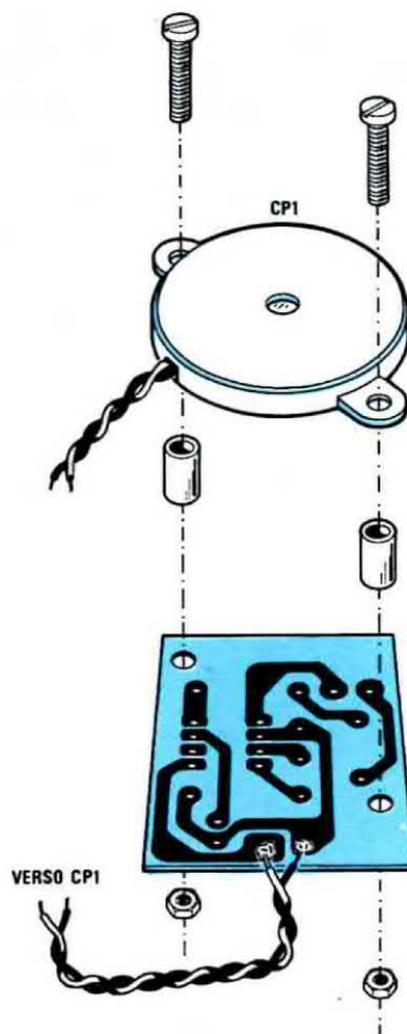
Fig. 4 Dal lato opposto del circuito stampato fisserete la cicalina piezoelettrica, che terrete sollevata dal circuito con due piccoli distanziatori cilindrici come visibile nel disegno.
