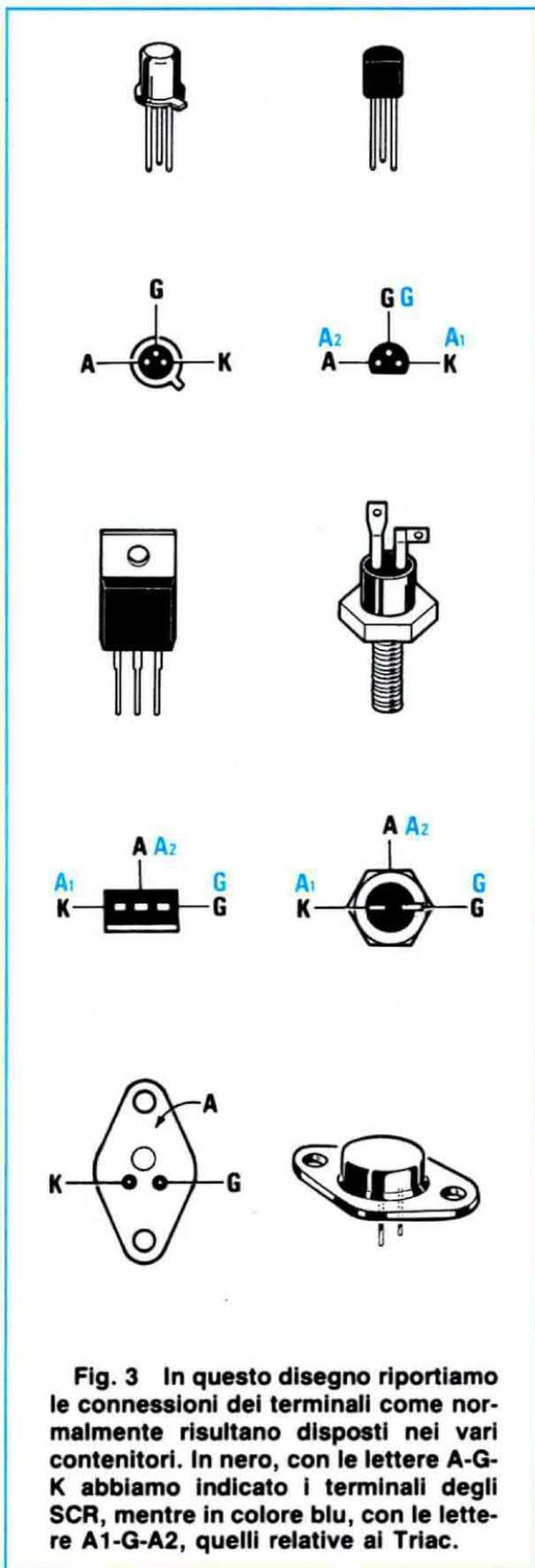
**Fig. 3** In questo disegno riportiamo le connessioni dei terminali come normalmente risultano disposti nei vari contenitori. In nero, con le lettere A-G-K abbiamo indicato i terminali degli SCR, mentre in colore blu, con le lettere A1-G-A2, quelli relative ai Triac.
