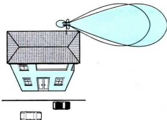
**Fig. 21** Il lobo in senso orizzontale di due antenne accoppiate sul piano verticale non subisce, eccetto l'aumento di guadagno, alcuna variazione.
