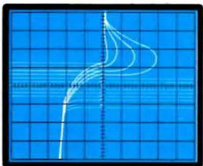
Fig. 26 Se la traccia verticale superiore non è ben definita, ma tondeggiate, sono invertiti G e A1.
