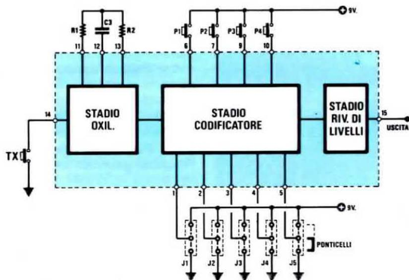
**Fig. 1** Schema a blocchi dell'integrato Encoder M.145026 utilizzato nel trasmettitore. Per codificare gli impulsi, dovrete collegare i piedini 1-2-3-4-5 in una delle tre posizioni Positivo, Massa o Aperto. Per eccitare il canale richiesto, dovrete premere assieme ad uno dei quattro pulsanti siglati P1-P2-P3-P4, anche il pulsante TX, per mettere in funzione lo stadio oscillatore. Nel nostro circuito il pulsante TX è stato sostituito da un transistor (vedi TR1 in fig.7).
