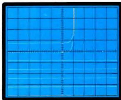
Fig. 20 Se si desidera una maggior precisione, si dovrà portare la 7ª riga verso il basso (cioè escludere le 6 righe negative) e modificare la sensibilità verticale dell'oscilloscopio da 0,5 a 0,2 volt.
