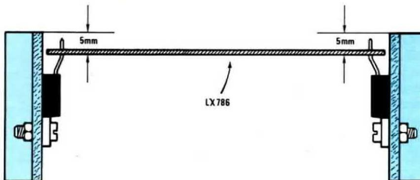
**Fig. 29** Per sostenere il circuito stampato all'interno del mobile, dovrete sfruttare il corpo dei tre Mos-Power e del diodo BY.359. Per evitare che, a operazione ultimata, il circuito risulti inclinato, fissate provvisoriamente il corpo di tali semiconduttori sulle alette, poi, livellato il circuito, potrete saldarne i terminali.
