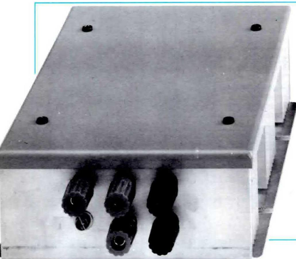
**Fig. 12** Sul frontale del mobile sono presenti 5 bocche che vi permetteranno, come vedesi nelle figg. 30 e 31, di passare con estrema facilità dall'accensione elettronica a quella tradizionale.
