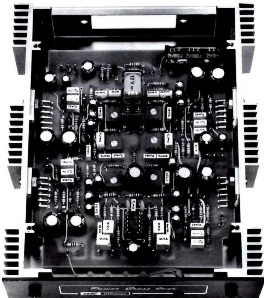
**Fig.3** Foto di un nostro prototipo già montato all'interno del mobile e completo di alette laterali di raffreddamento per gli integrati TDA.2009.
