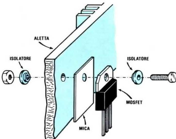
**Fig. 20** La parte metallica del corpo dei Mos-Power e anche quella del diodo BY.359, debbono risultare elettricamente isolate dall'aletta di raffreddamento, pertanto, come vedesi in figura, dovrete utilizzare l'apposita mica isolante e le rondelle isolanti presenti nel kit.
