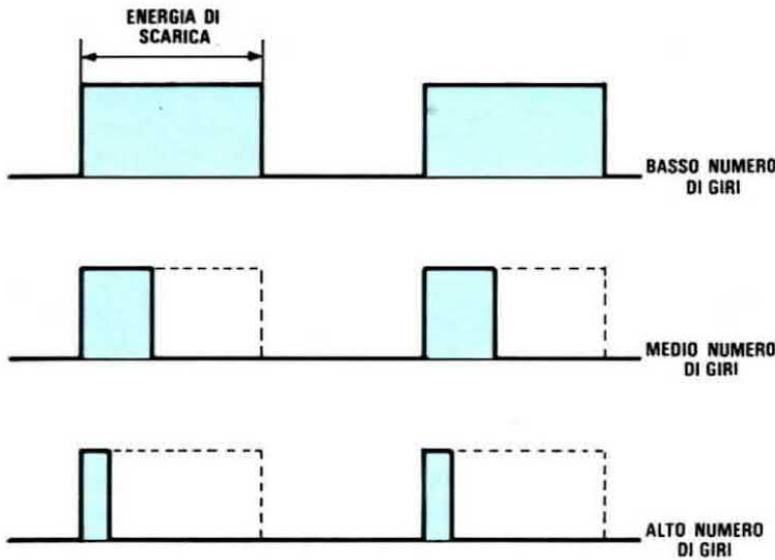
**Fig. 5** L'energia di "scarica" di una accensione tradizionale risulta molto elevata a basso numeri di giri, però, come vedesi in tale disegno, si riduce notevolmente con l'aumentare del numero di giri, pertanto alle alte velocità si ha un maggior consumo di carburante.
