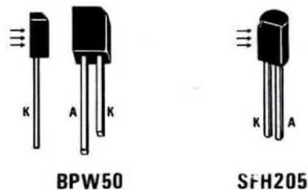
**Fig. 4 Il lato sensibile del fototransistor BPW50 è quello visto frontalmente tenendo il terminale K (più corto) sulla sinistra. Nel caso dell'SFH.205 è la parte piatta del corpo (in questo caso il catodo si trova a sinistra).**
