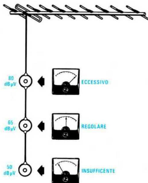
**Fig. 1** Un segnale TV, passando attraverso un cavo coassiale, subisce una attenuazione di circa 0,25 dB per metro. Se non si adottano particolari accorgimenti, nelle prese più vicine all'antenna avremo un segnale "eccessivo", in grado di saturare la TV, mentre in quelle più lontane un segnale "insufficiente".
