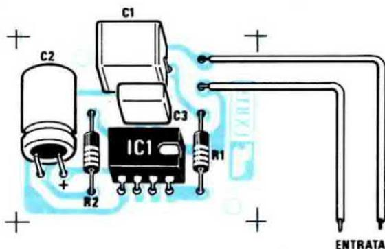
Fig. 3 Schema pratico di montaggio della cicalina vista dal lato dei componenti.
