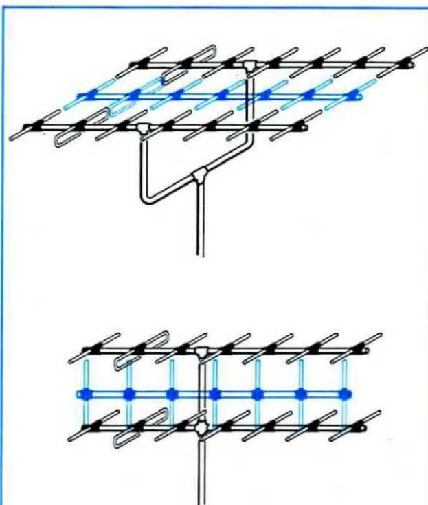
**Fig. 25** La spaziatura "minima" tra due antenne accoppiate sia sul piano orizzontale che su quello verticale, non dovrà mai risultare inferiore alla larghezza di UNA antenna e mai superiore alla larghezza di TRE antenne.
