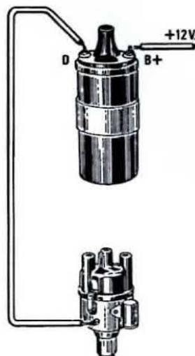
**Fig. 1** L'accensione presente in quasi tutte le autovetture è di tipo tradizionale, cioè, come raffigurato qui sopra, è composta da una bobina di Alta Tensione collegata con una estremità alla tensione positiva di 12 volt e con l'altra alle puntine presenti all'interno dello spinterogeno.
