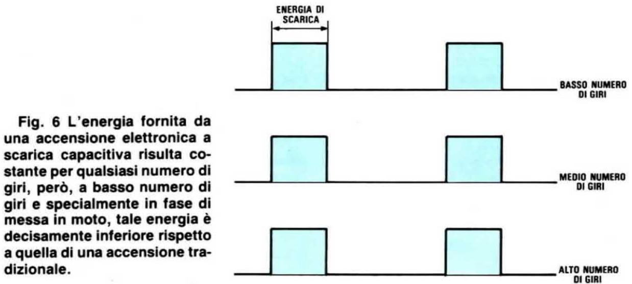
**Fig. 6** L'energia fornita da una accensione elettronica a scarica capacitiva risulta costante per qualsiasi numero di giri, però, a basso numero di giri e specialmente in fase di messa in moto, tale energia è decisamente inferiore rispetto a quella di una accensione tradizionale.
