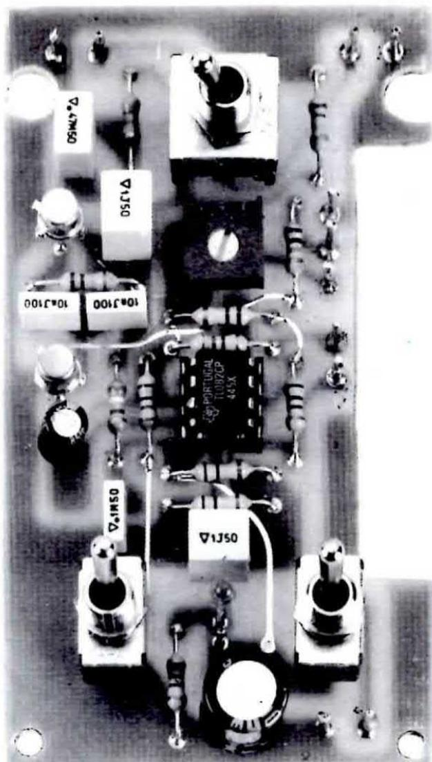
**Fig.3** In questa foto ingrandita potrete facilmente osservare come risultano disposti tutti i componenti e in che posizione dovrete inserire i tre deviatori a levetta.
