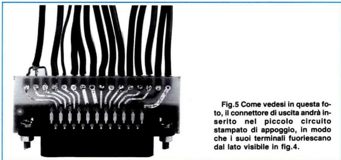
**Fig.5** Come vedesi in questa foto, il connettore di uscita andrà inserito nel piccolo circuito stampato di appoggio, in modo che i suoi terminali fuoriescano dal lato visibile in fig.4.
