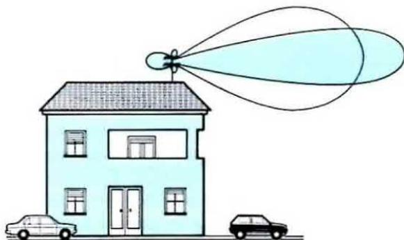
**Fig. 20** Con due antenne accoppiate sul piano verticale il lobo verticale si restringerà notevolmente e ciò permetterà di attenuare tutte le interferenze provenienti dal basso.
