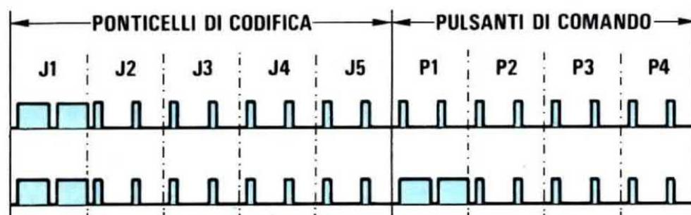
**Fig. 6** Se il piedino di codifica 1 risultasse collegato tramite J1 al positivo di alimentazione, già i primi due impulsi risulterebbero LARGHI e quello relativo al pulsante P1 lo diverrebbe solo premendo tale pulsante.
