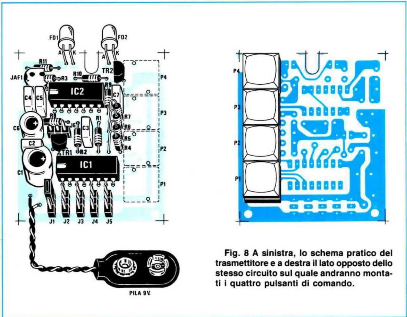
Fig. 8 A sinistra, lo schema pratico del trasmettitore e a destra il lato opposto dello stesso circuito sul quale andranno montati i quattro pulsanti di comando.
