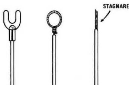
**Fig. 32** Per collegare i fili provenienti dalla bobina AT e dallo spinterogeno alle boccole serrafilo presenti nel mobile (vedi fig.12), potrete utilizzare delle banane o, ancor meglio, eseguire sulle estremità del filo un occhiello o fissare un capofilo come vedesi in figura.
