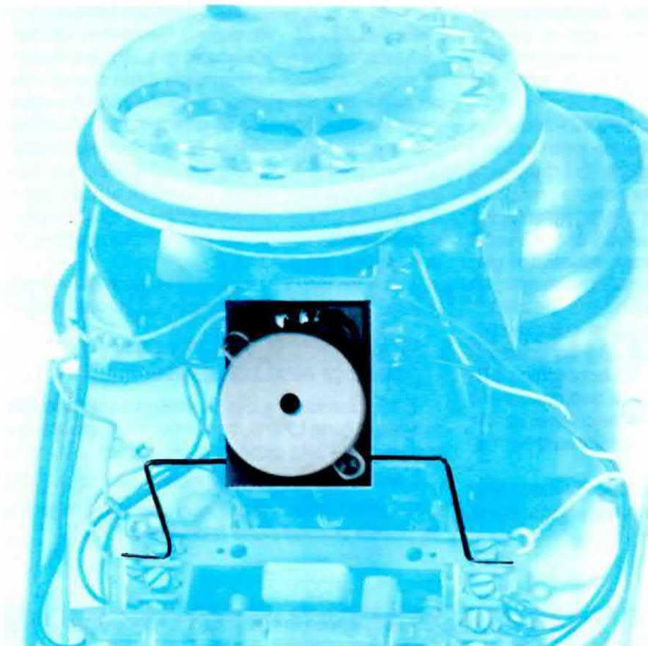
**Fig.5** La cicalina andrà collocata all'interno del telefono e i suoi due fili collegati alle due prime viti serrafilo presenti nella morsettiere visibile nella foto. In tutti i telefoni in nostro possesso i fili del campanello meccanico fanno capo a queste due viti.
