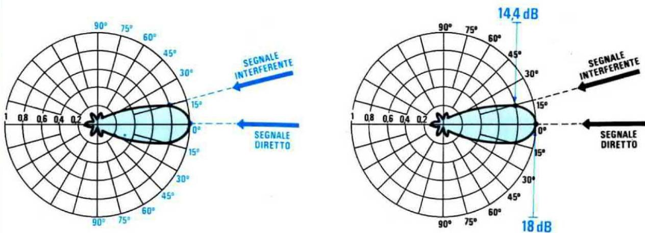
**Fig. 14** Un segnale "interferente", sia esso un'onda riflessa o il segnale di un'altra emittente, non raggiunge mai la nostra antenna sul lato frontale, ma quasi sempre lateralmente. Se l'antenna ha un guadagno di 18 dB ed il segnale interferente viene captato sul "lobo x 0,8" (vedi grafico a destra), tale segnale subisce un guadagno di ben 14,4 dB.
