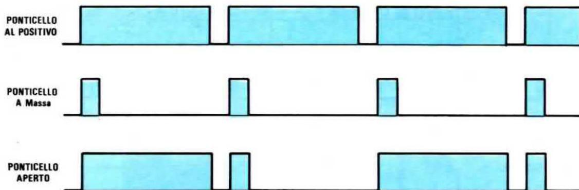
**Fig. 3** I piedini 1-2-3-4-5 se collegati al positivo di alimentazione generano un impulso **LARGO**, se collegati a massa un impulso **STRETTO**, se tenuti aperti un impulso **LARGO** seguito da uno **STRETTO**. La stessa forma d'onda si ottiene anche con i piedini collegati ai pulsanti P1-P2-P3-P4.
