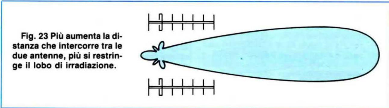
Fig. 23 Più aumenta la distanza che intercorre tra le due antenne, più si restringe il lobo di irradiazione.
