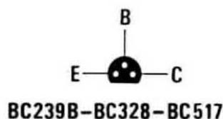
Fig. 2 Connessioni degli integrati impiegati in tale progetto visti da sopra e dei transistor visti invece da sotto. Vi ricordiamo che il BC239 è un NPN, il BC.238 un PNP e il BC.517 un darlington NPN.
