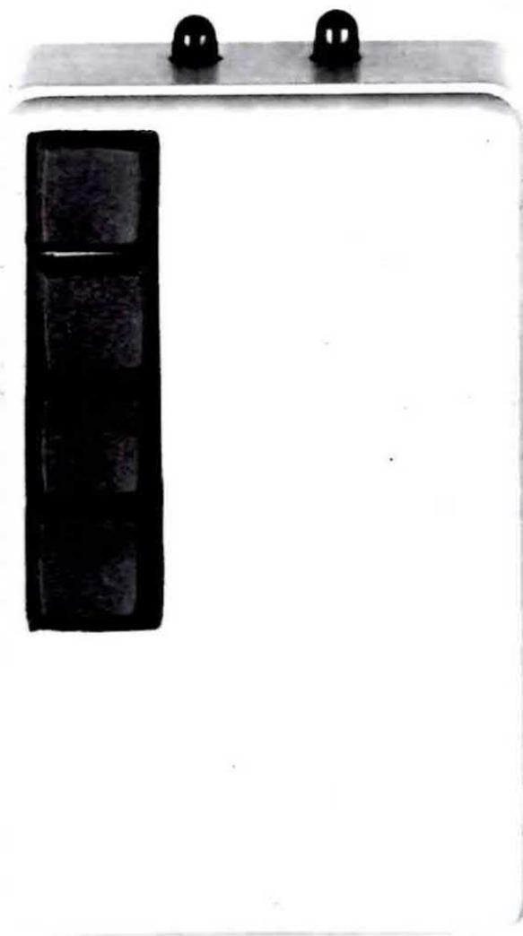
Fig.11 Per far invece fuoriuscire i quattro pulsanti di comando dalla scatola, dovreste praticare su quest'ultima un'asola rettangolare servendovi di una sottile punta da trapano. Il perimetro verrà poi rifinito.
