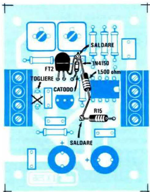
**Fig. 3** Per rendere più stabile il cercametri LX.756 occorre aggiungere una resistenza da 1.500 ohm ed un diodo 1N4150 collegati come vedesi in figura. I prossimi circuiti stampati che forniremo risulteranno già modificati per ricevere questi due componenti aggiuntivi. **NOTA** = Il condensatore ceramico C3, posto vicino alla morsettiera di sinistra, andrà eliminato.
