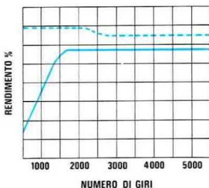
**Fig. 3** Poichè nella normale accensione elettronica la carica viene immagazzinata in un condensatore e non nella bobina AT, il rendimento risulta più lineare, anche se a basso numero di giri è sempre inferiore rispetto a quello fornito dall'energia induttiva come vedesi nel diagramma sopraportato.
