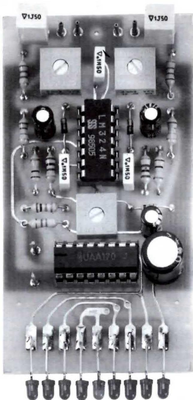
**Fig.1** Foto ingrandita del VU-Meter differenziale Stereo a diodi led, che potrà essere installato su amplificatori, radio, mangianastri, ecc. I terminali dei diodi led, come vedesi in questa foto, andranno infilati frontalmente nel circuito stampato.
