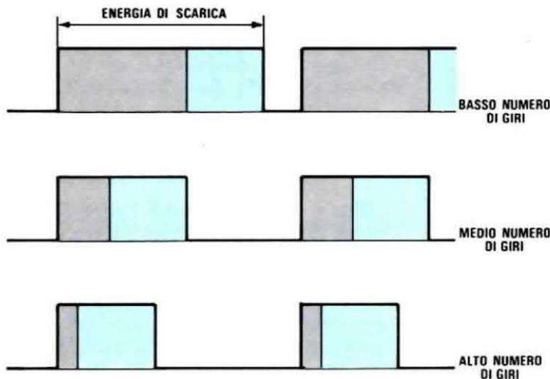
**Fig. 7** L'energia fornita dall'accensione Turbo-Japan come vedesi in questo disegno, risultando la somma di una scarica induttiva e di una capacitiva, in fase di messa in moto risulta doppia. Aumentando la velocità si otterrà sempre una energia maggiore rispetto a quella fornita da una normale accensione capacitiva.
