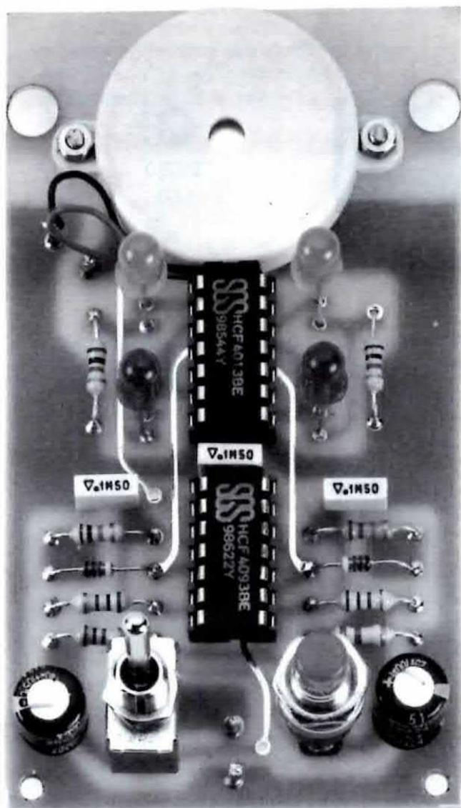
Fig.2 Qui sopra la foto ingrandita di uno dei nostri prototipi, a destra, lo schema pratico di montaggio utile per individuare la posizione dei vari componenti. I terminali K dei diodi led vanno rivolti verso la presa pila.
