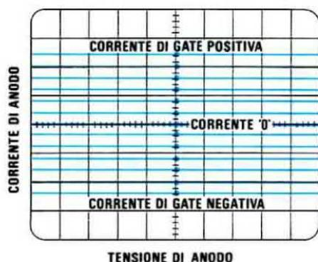
Fig. 6 Ogni riga orizzontale che apparirà sullo schermo dell'oscilloscopio (vedi figg. 16 - 17 - 18) corrisponderà ad un diversa "corrente di Gate", che ricaverete facilmente in funzione dei pulsanti "corrente di Base" premuti sul tracciacurve. Ricordatevi che la 7ª riga corrisponde a "corrente 0", pertanto le 6 righe sopra sono le correnti "positive" e le 6 righe sotto le correnti "negative".
