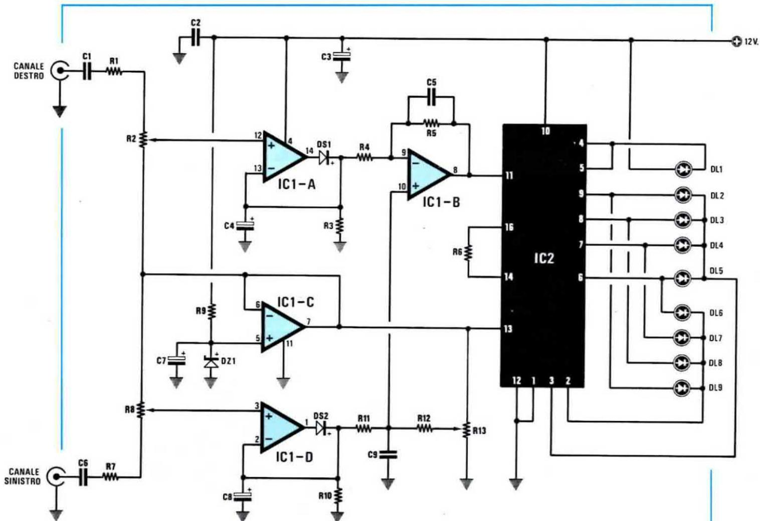
Fig.2 Schema elettrico del VU-Meter differenziale. Come spiegato nell'articolo, il trimmer R13 andrà ruotato fino a riuscire ad accendere il diodo led centrale, senza inserire alcun segnale nei due ingressi.
