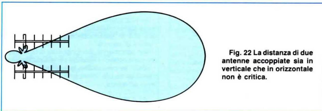
Fig. 22 La distanza di due antenne accoppiate sia in verticale che in orizzontale non è critica.
