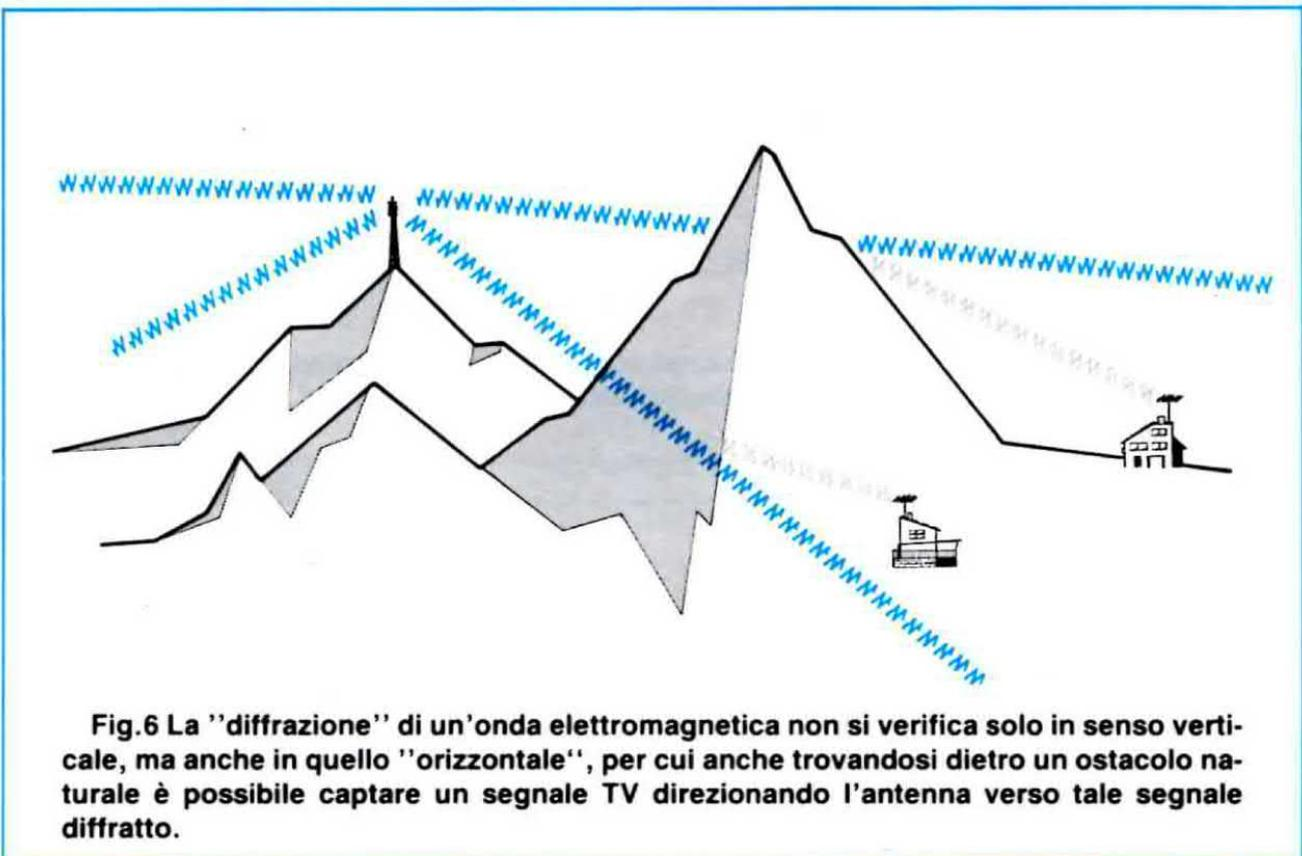
**Fig.6** La "diffrazione" di un'onda elettromagnetica non si verifica solo in senso verticale, ma anche in quello "orizzontale", per cui anche trovandosi dietro un ostacolo naturale è possibile captare un segnale TV direzionando l'antenna verso tale segnale diffratto.
