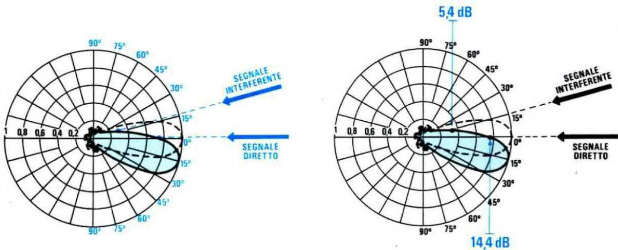
**Fig. 15** Ruotando l'antenna di pochi gradi, si riesce spesso ad eliminare totalmente l'onda riflessa o interferente. Osservando il grafico di destra è facile intuirne il motivo. Infatti, anche se il segnale diretto subisce ora un leggera attenuazione (guadagno 14,4 dB anzichè 18), quella del segnale "interferente" è elevata (guadagno 5,4 dB anzichè 14,4).
