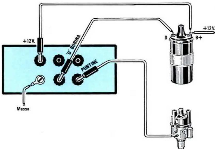
**Fig. 31** In caso di avaria potrete facilmente reinserire nella vostra auto la tradizionale accensione ed escludere quella elettronica, spostando le due boccole sopra "D bobina AT" e "puntine" sulle due boccole poste in basso. Queste due boccole andranno collegate internamente insieme, per congiungere il D della bobina alle puntine dello spinterogeno.
