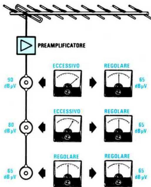
**Fig. 2** Per riuscire a far giungere alla "presa più distante" 65 dBmicrovolt, occorre preamplificare il segnale d'antenna, ma in questo modo aumenterà ancora di più il segnale sulle prese più vicine all'antenna. Per equilibrare il segnale su tutte le prese occorre utilizzare delle apposite "prese attenuatrici".
