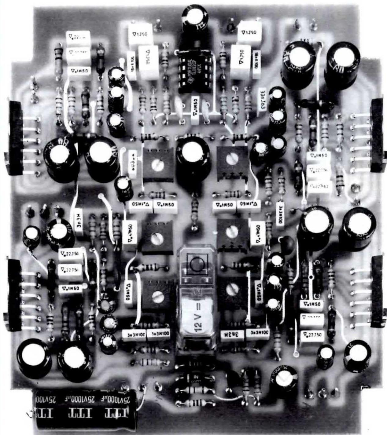
**Fig.4** A sinistra lo schema pratico di montaggio dell'amplificatore. Facciamo notare che il connettore visibile in basso va montato in modo che i suoi terminali fuoriescano dal lato in cui sono riportate le piste di attacco per i fili che provengono dal circuito stampato base. Qui sopra, la foto di un altro esemplare da noi montato per il reparto di collaudo. Il circuito stampato definitivo è completo di disegno serigrafico e protetto con una speciale vernice.
