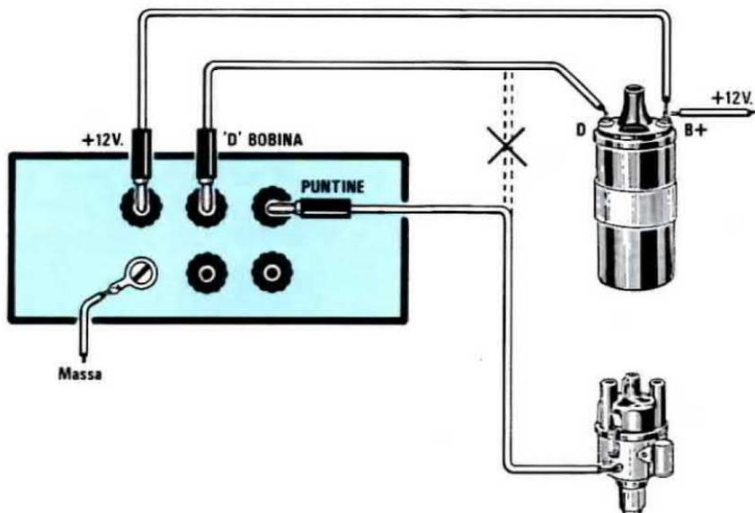
**Fig. 30** Per collegare questa accensione Turbo-Japan alla vostra auto, dovrete semplicemente collegare il filo che parte dallo Spinterogeno alla prima boccola di destra indicata "puntine", poi collegare alla seconda boccola il filo D della bobina AT, e all'ultima, posta a sinistra, i 12 volt della batteria, che potrete sempre prelevare dal terminale B+ della stessa bobina.
