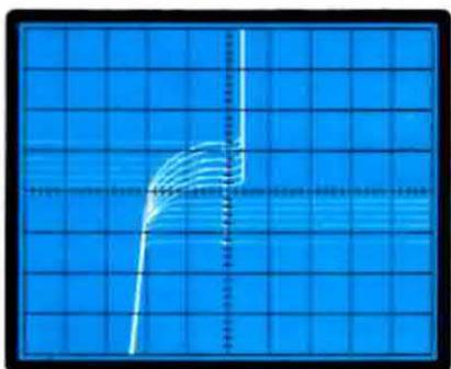
Fig. 29 Se le due tracce partono entrambe dalla 7ª traccia, significa che la corrente di Gate è eccessiva.
