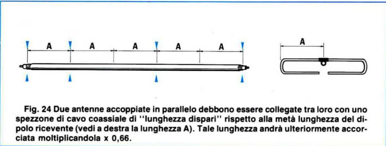
Fig. 24 Due antenne accoppiate in parallelo debbono essere collegate tra loro con uno spezzone di cavo coassiale di "lunghezza dispari" rispetto alla metà lunghezza del dipolo ricevente (vedi a destra la lunghezza A). Tale lunghezza andrà ulteriormente accorciata moltiplicandola x 0,66.
