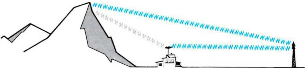
**Fig. 9** Un'onda elettromagnetica, scontrandosi con un ostacolo, viene sempre "riflessa" e giungendo sull'antenna in ritardo rispetto all'immagine diretta, determina nella TV delle immagini sdoppiate.
