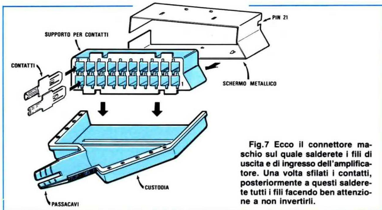
**Fig.7** Ecco il connettore maschio sul quale salderete i fili di uscita e di ingresso dell'amplificatore. Una volta sfilati i contatti, posteriormente a questi salderete tutti i fili facendo ben attenzione a non invertirli.
