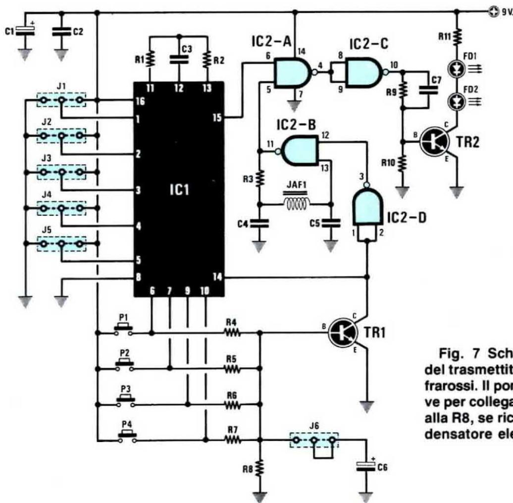
Fig. 7 Schema elettrico del trasmettitore a raggi infrarossi. Il ponticello J6 serve per collegare in parallelo alla R8, se richiesto, il condensatore elettrolitico C6.
