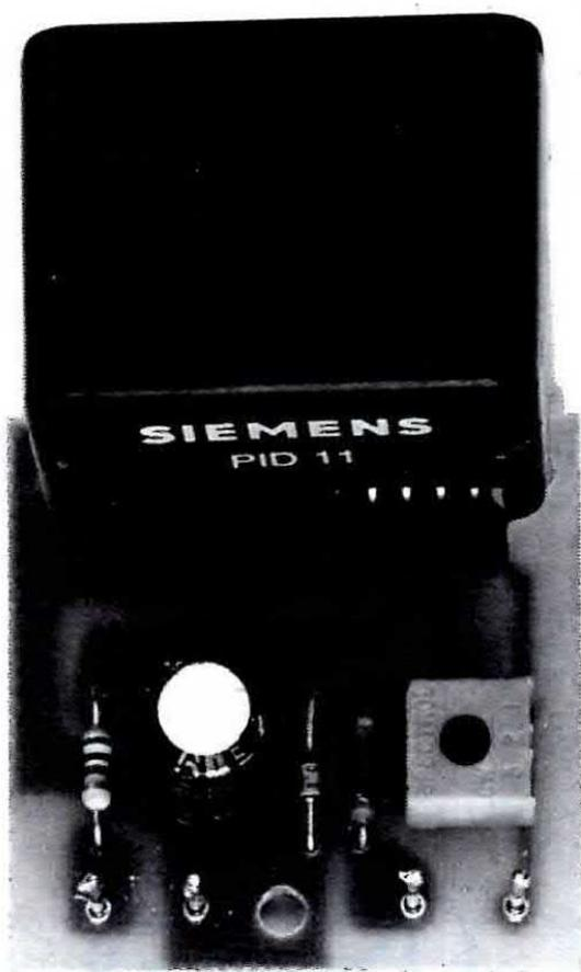
**Fig.9** Foto di uno dei tanti esemplari da noi montati per il collaudo. Considerata la sua semplicità, in brevissimo tempo tutti saranno in grado di montarlo e di farlo funzionare. Il trimmer R1 serve per modificare la sensibilità.
