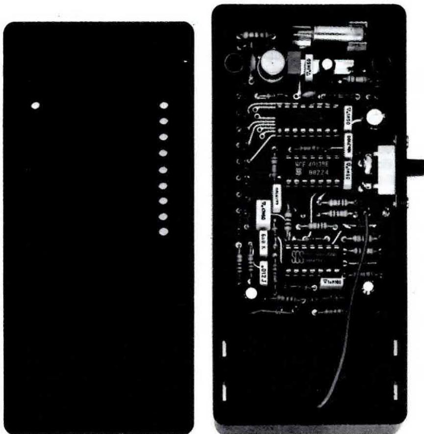
**Fig.9** Inserito il circuito stampato entro il mobile, dovete praticare dei fori sul suo coperchio per far fuoriuscire la testa dei diodi led.
