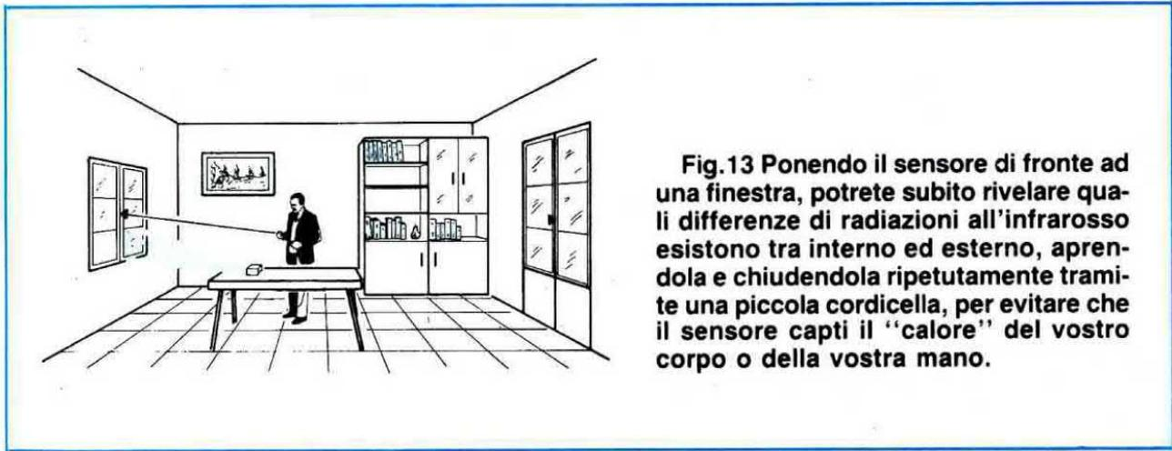
Fig.13 Ponendo il sensore di fronte ad una finestra, potrete subito rivelare quali differenze di radiazioni all'infrarosso esistono tra interno ed esterno, aprendola e chiudendola ripetutamente tramite una piccola cordicella, per evitare che il sensore capti il "calore" del vostro corpo o della vostra mano.
