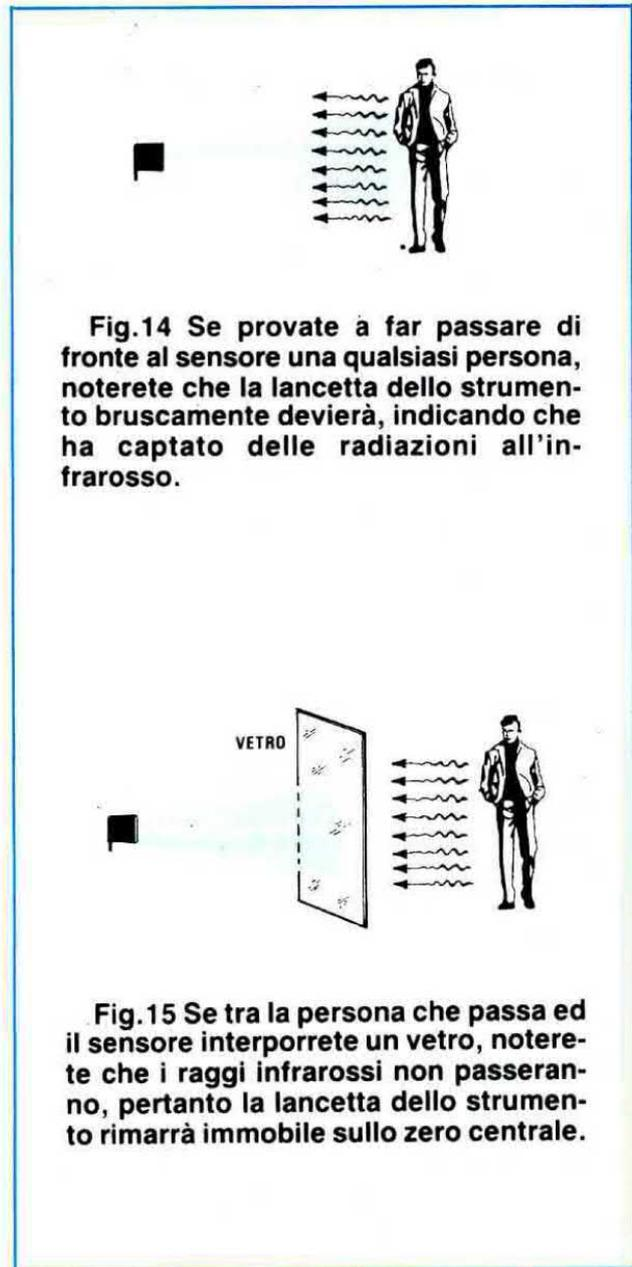
Fig.14 Se provate a far passare di fronte al sensore una qualsiasi persona, noterete che la lancetta dello strumento bruscamente devierà, indicando che ha captato delle radiazioni all'infrarosso.
