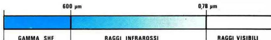
**Fig.1 I raggi infrarossi sono in pratica delle radiazioni ad altissima frequenza. Come vedesi in tale disegno, alle SHF (Super High Frequency) seguono i raggi infrarossi, quindi i raggi visibili, cioè la luce.**
