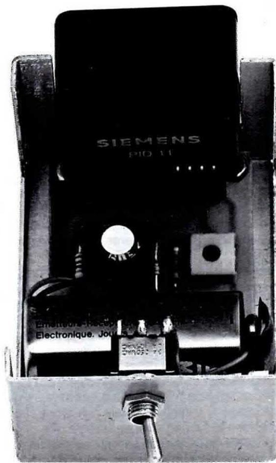
**Fig.10** Il circuito stampato andrà fissato all'interno del piccolo contenitore di alluminio, tenendolo leggermente distanziato dal fondo per non creare dei cortocircuiti. Si noti la posizione scelta per la pila di alimentazione da 9 volt.
