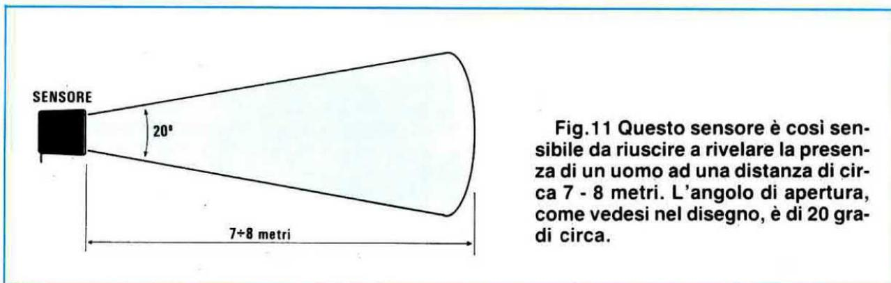
Fig.11 Questo sensore è così sensibile da riuscire a rivelare la presenza di un uomo ad una distanza di circa 7 - 8 metri. L'angolo di apertura, come vedesi nel disegno, è di 20 gradi circa.
