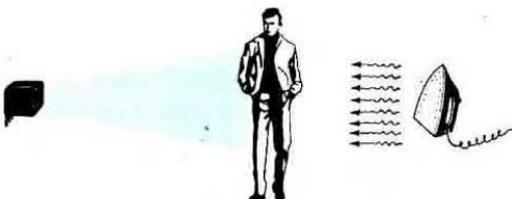
**Fig.18** Con il ferro da stiro acceso, e dopo che la lancetta si sarà fermata sullo 0 centrale, provate a passarvi di fronte e vedrete che la lancetta indicherà una riduzione di raggi infrarossi.
