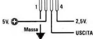
Fig.4 Dei quattro terminali che fuoriescono dalla parte posteriore del sensore, i due di sinistra servono per alimentare con una tensione di 5 volt il circuito interno, mentre i due di destra, per prelevare il segnale di "uscita" e la tensione di riferimento.
