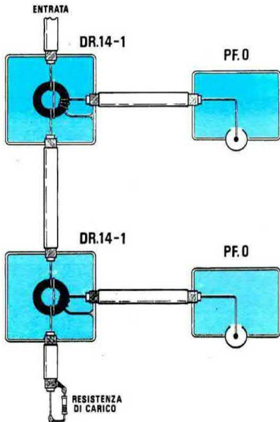
Fig.144 Le prese PF.Ø, cioè quelle sprovviste internamente di un attenuatore, si possono utilizzare solo se precedute da un Derivatore o da una presa PP.4,2 (vedi fig.146), perchè tutti i disturbi spurii irradiati dalla TV collegata alla presa PF.0 verranno bloccati dall'elevata attenuazione inversa di cui questi componenti dispongono.
