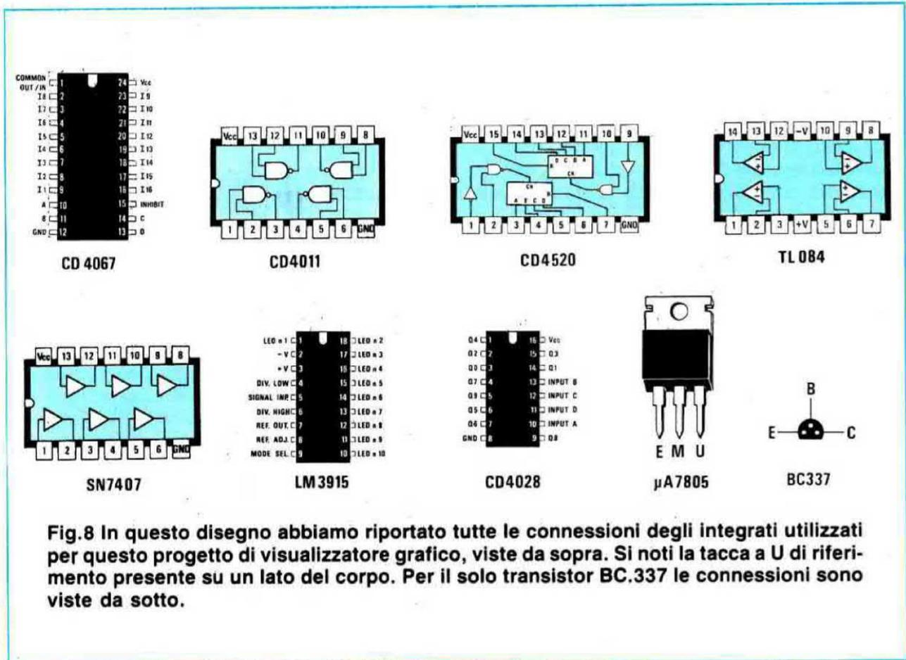
**Fig. 8** In questo disegno abbiamo riportato tutte le connessioni degli integrati utilizzati per questo progetto di visualizzatore grafico, viste da sopra. Si noti la tacca a U di riferimento presente su un lato del corpo. Per il solo transistor BC.337 le connessioni sono viste da sotto.
