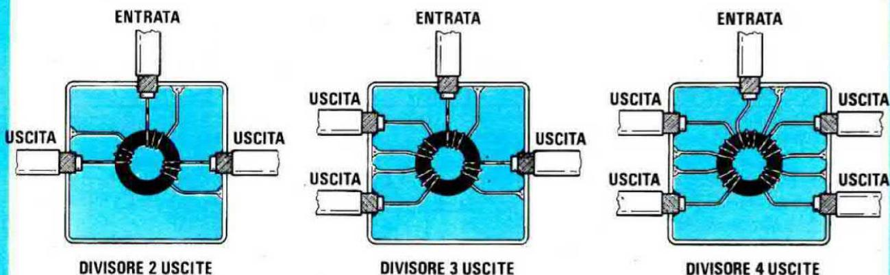
Fig.111 Nei Divisori di tipo "induttivo", la suddivisione si effettua tramite induttanze avvolte su nucleo in ferrite. Questi divisori sono gli unici che dovrete adottare, perchè evitano che i disturbi spurii presenti su una linea raggiungano l'altra linea di discesa.
