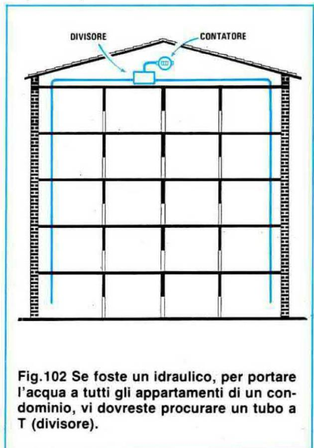
Fig.102 Se foste un idraulico, per portare l'acqua a tutti gli appartamenti di un condominio, vi dovrete procurare un tubo a T (divisore).
