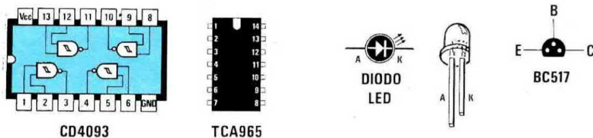
**Fig.10** Connessioni dei due integrati utilizzati in questo progetto visti da sopra e del solo transistor BC.517 visto invece da sotto. Per il diodo led ricordatevi che il terminale più corto è l'Anodo.
