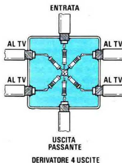
Fig.116 I Derivatori "resistivi" anche se si trovano ancora in vendita solo perchè più economici, non conviene mai usarli, perchè, avendo una attenuazione inversa inferiore ai tipi Ibridi ed Induttivi, tutti i disturbi generati da una TV possono facilmente trasferirsi sulla linea e disturbare così altri televisori (vedi figg.141 - 142 - 143).
