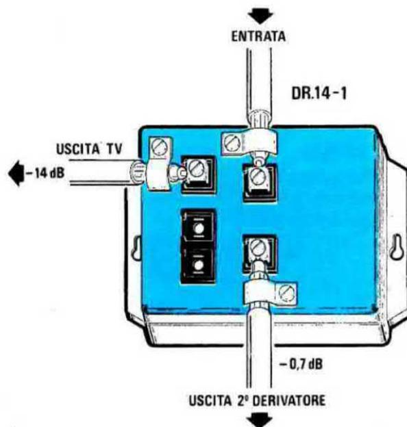
Fig.121 In un Derivatore modello DR.14-2 sono presenti una presa d'ingresso, due di uscita per la TV ed una di passaggio. L'attenuazione di prelievo TV rimarrà sempre fissa sul 14 dB, mentre aumenta l'attenuazione di passaggio che, rispetto alla prima di 0,7 dB, passa in questo modello a 1,8 dB.
