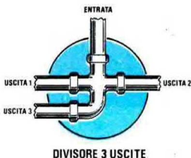
**Fig.105** Se le colonne di discesa dovessero essere 3, vi dovrete procurare un raccordo, provvisto di un tubo d'ingresso e di tre di uscita come vedesi in figura.
