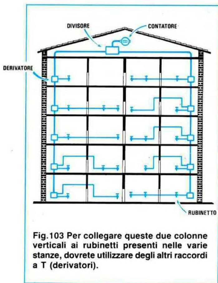
Fig.103 Per collegare queste due colonne verticali ai rubinetti presenti nelle varie stanze, dovrete utilizzare degli altri raccordi a T (derivatori).
