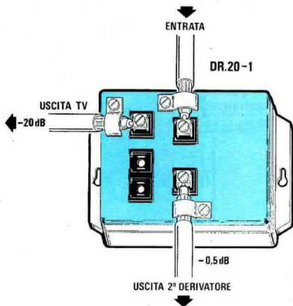
Fig.123 In un Derivatore modello DR.20-1 vi sono una presa d'ingresso, una di uscita TV ed una di passaggio. Su quella di prelievo per la TV sarà presente un'attenuazione di uscita pari a 20 dB, mentre su quella di proseguimento per i successivi Derivatori, una attenuazione di soli 0,5 dB.
