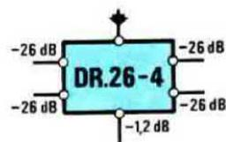
Derivatori con 1-2-4 uscite, tutte con attenuazioni di prelievo di - 26 dB.
