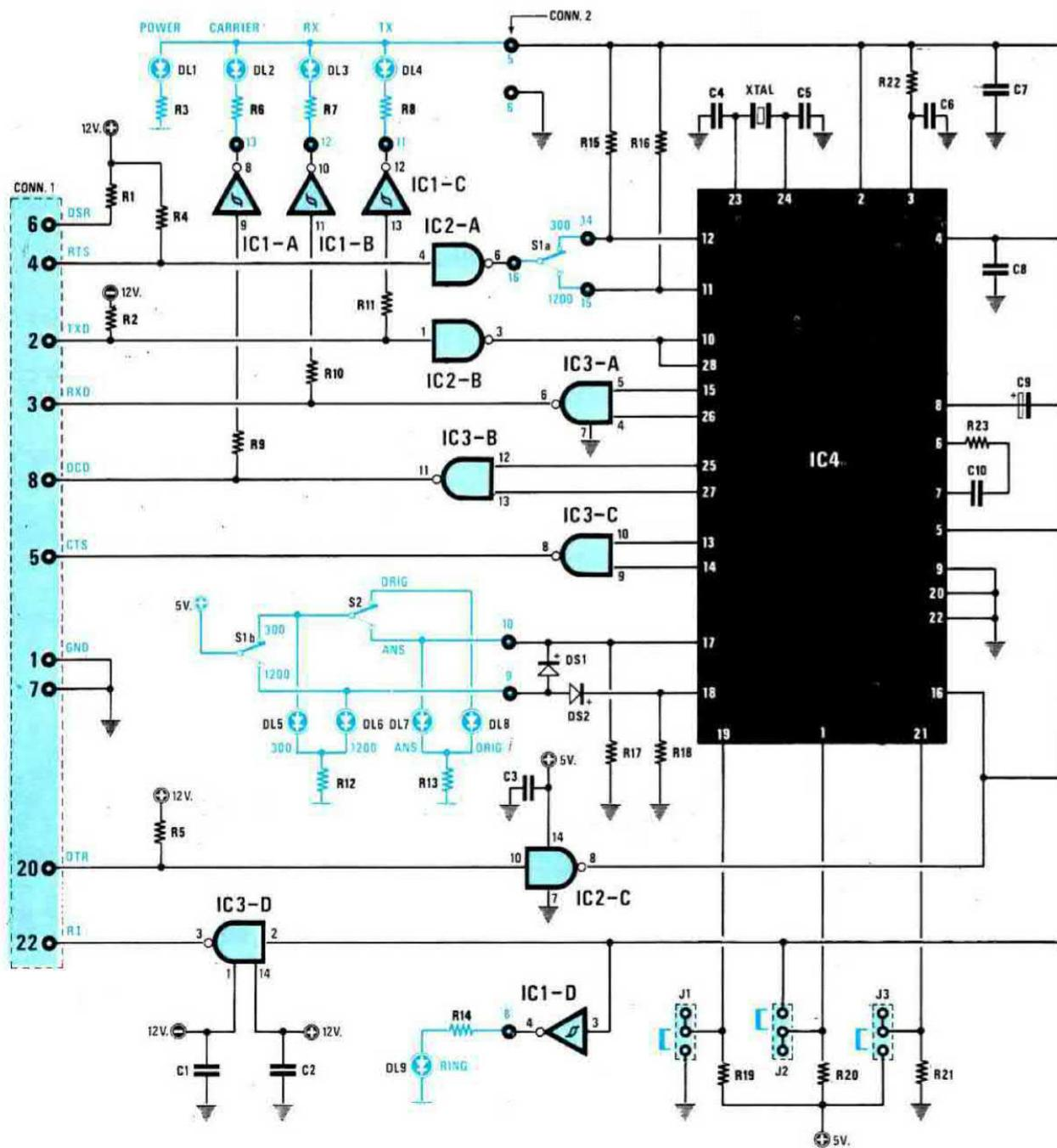
Fig.1 Schema elettrico completo del nostro Modem che, potendo lavorare da 300 Baude a 1.200 Baude, vi permetterà di collegarvi con qualsiasi utente sia in Half-Duplex che in Full-Duplex, in CCITT-V.21, CCITT-V.23, BELL-103, BELL-202. Questo Modem, come spiegato nell'articolo, dispone di un AUTO-TEST. La lista dei componenti è riportata a pag.83.
