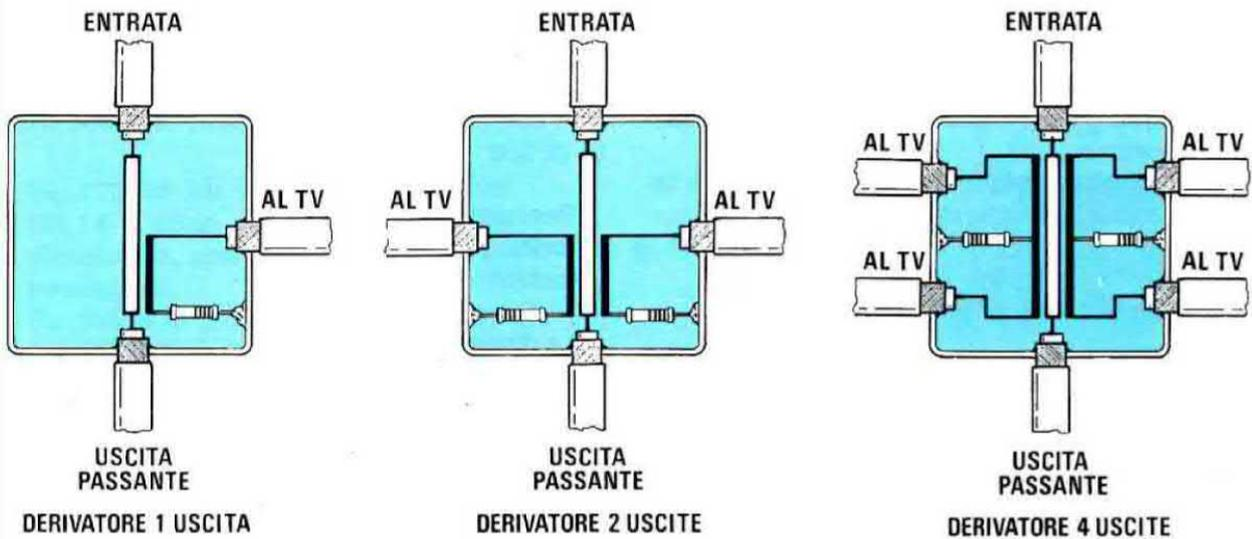
**Fig.117 I Derivatori Ibridi** anche se sono caratterizzati da un'elevata attenuazione inversa, presentano l'inconveniente di avere un solo valore di attenuazione di prelievo, -14 dB, e questo rende difficoltosa la progettazione di un impianto.
