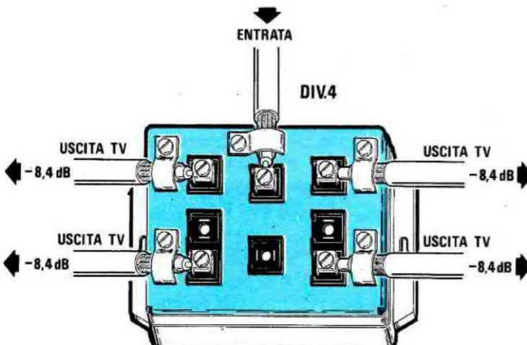
Logicamente, se sull'ingresso di questi Divisori applicheremo segnali di ampiezza diversa, pari ad esempio a 93 - 96 - 100 dBmicrovolt, sulle uscite preleveremo un segnale minore di -4,2 o -8,4 rispetto a quello inserito.
