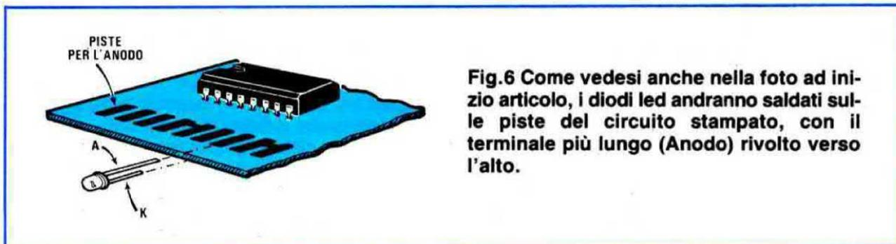
**Fig.6** Come vedesi anche nella foto ad inizio articolo, i diodi led andranno saldati sulle piste del circuito stampato, con il terminale più lungo (Anodo) rivolto verso l'alto.
