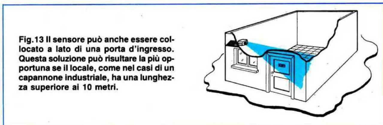
**Fig.13** Il sensore può anche essere collocato a lato di una porta d'ingresso. Questa soluzione può risultare la più opportuna se il locale, come nei casi di un capannone industriale, ha una lunghezza superiore ai 10 metri.
