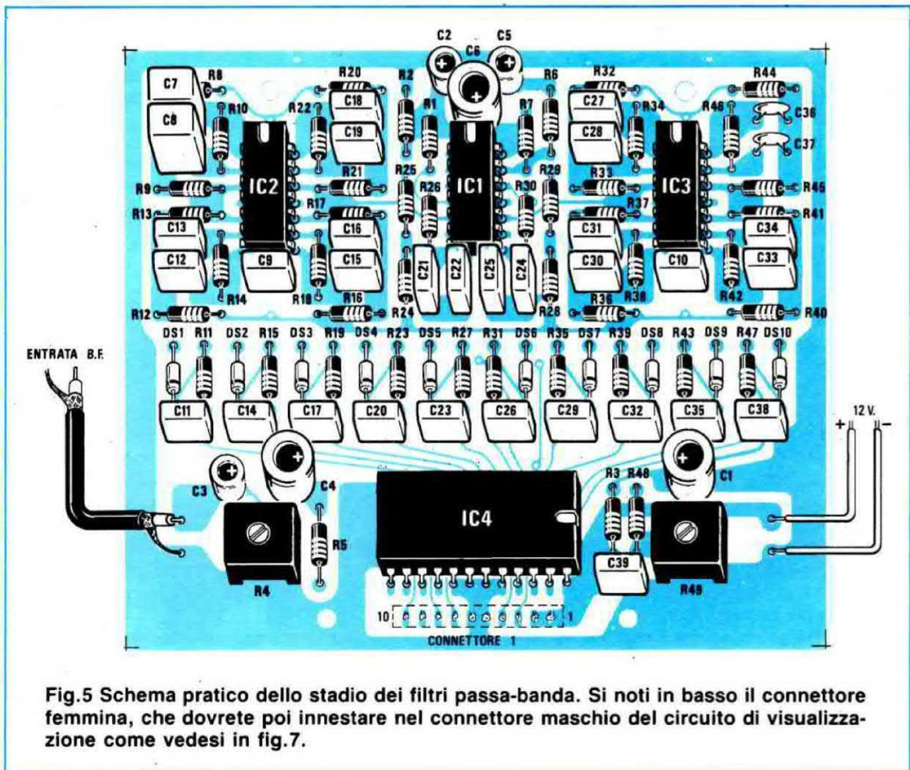
Fig.5 Schema pratico dello stadio dei filtri passa-banda. Si noti in basso il connettore femmina, che dovrete poi innestare nel connettore maschio del circuito di visualizzazione come vedesi in fig.7.
