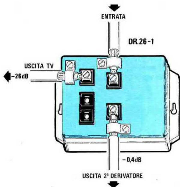
Fig.126 In un Derivatore modello DR.26-1 abbiamo una presa d'ingresso, una di uscita TV ed una di passaggio. Su quella di prelievo per la TV, essendo questo un modello DR.26, sarà presente una attenuazione di 26 dB.
