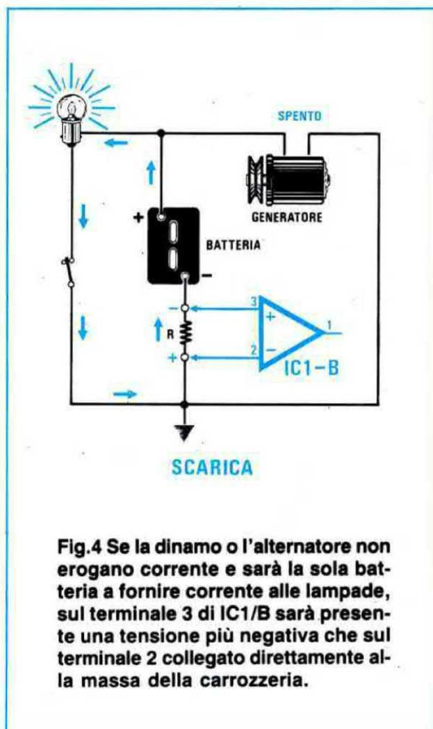
IC1/B per avere sulla sua uscita, in assenza di assorbimento, una tensione di 1 volt.
