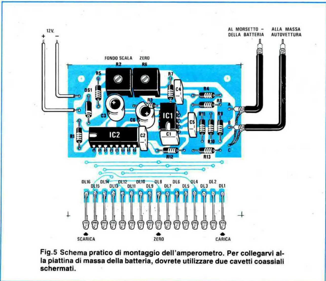
Fig.5 Schema pratico di montaggio dell'amperometro. Per collegarvi alla piattina di massa della batteria, dovrete utilizzare due cavetti coassiali schermati.
