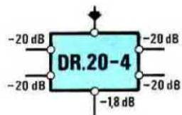
Derivatori con 1-2-4 uscite, tutte con attenuazioni di prelievo di - 20 dB.
