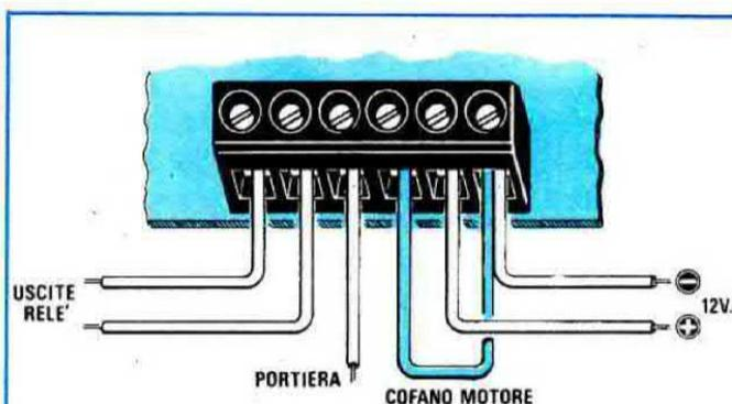
Fig.6 Per provare al banco questo antifurto, sarà sufficiente cortocircuitare per un istante il filo "cofano motore" su morsetto negativo.
