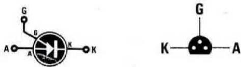
Fig.22 I transistor "unigiunzione programmabili", a differenza di quelli di tipo normale, vengono disegnati come visibile in figura, contraddistinguendo i tre terminali con le lettere K - G - A.
