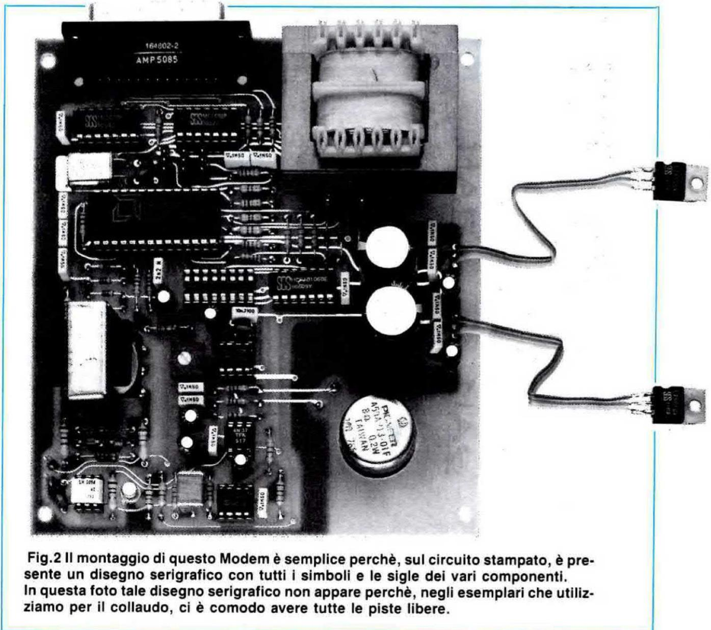
Fig.2 Il montaggio di questo Modem è semplice perchè, sul circuito stampato, è presente un disegno serigrafico con tutti i simboli e le sigle dei vari componenti. In questa foto tale disegno serigrafico non appare perchè, negli esemplari che utilizziamo per il collaudo, ci è comodo avere tutte le piste libere.
