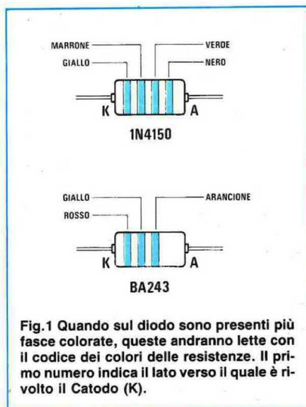
Fig.1 Quando sul diodo sono presenti più fasce colorate, queste andranno lette con il codice dei colori delle resistenze. Il primo numero indica il lato verso il quale è rivolto il Catodo (K).
