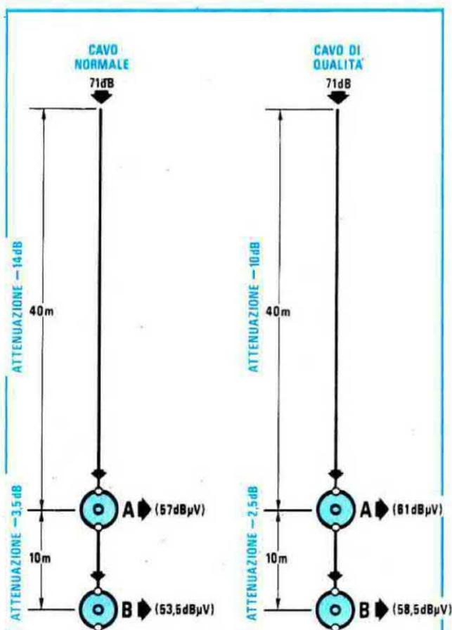
**Fig.150** Se un impianto è stato utilizzato per la linea di discesa del cavo coassiale "normale" (figura di sinistra), è probabile che sulle prese non giunga un segnale sufficiente. Sostituendo il cavo coassiale con uno di qualità (figura di destra) riuscirete, con una modica spesa, a raddoppiare il livello di tensione.
