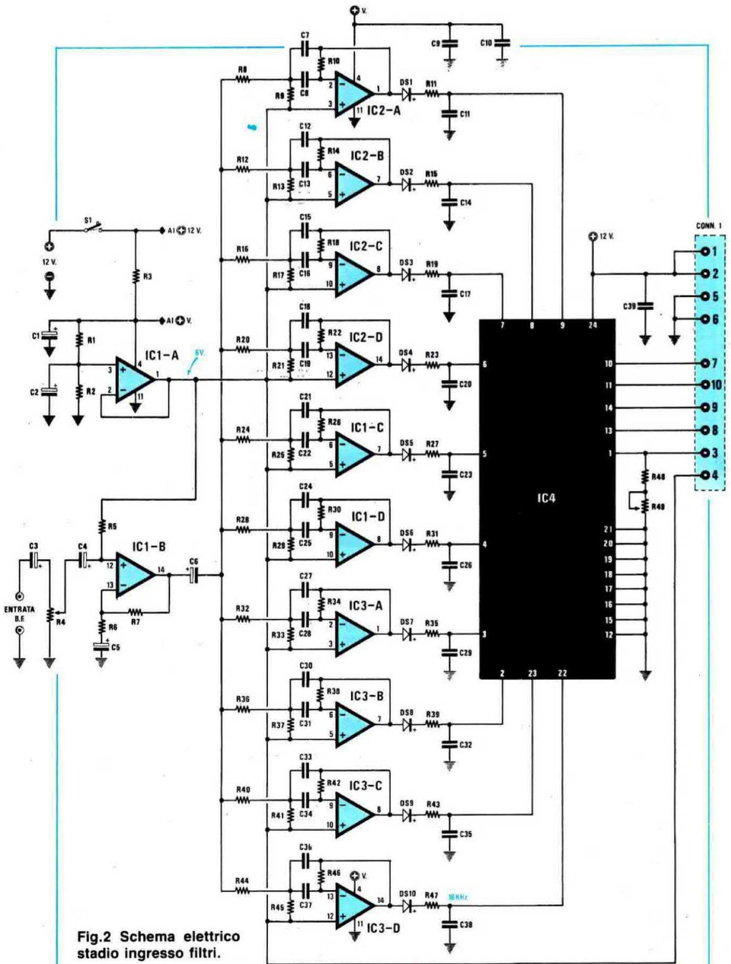
Fig.2 Schema elettrico stadio ingresso filtri.
