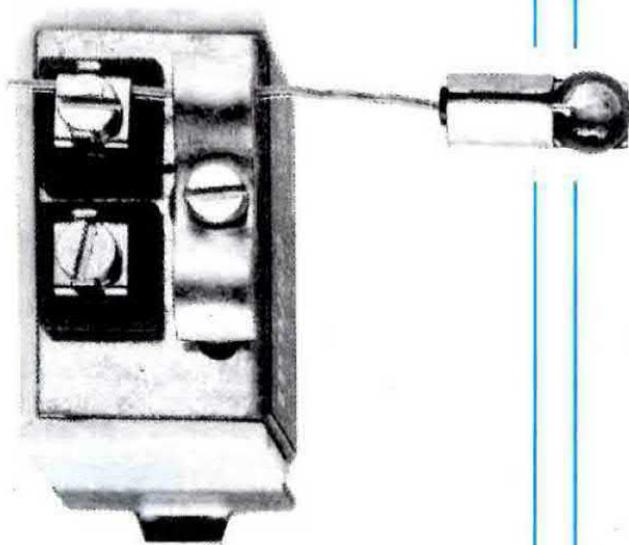
**Fig.148** Le resistenze di carico da 75 ohm da inserire nei morsetti di uscita possono avere forme e supporti diversi a seconda della Casa che le costruisce. In figura, vi facciamo vedere un modello molto pratico ed economico che verrà bloccato dal serracavo.
