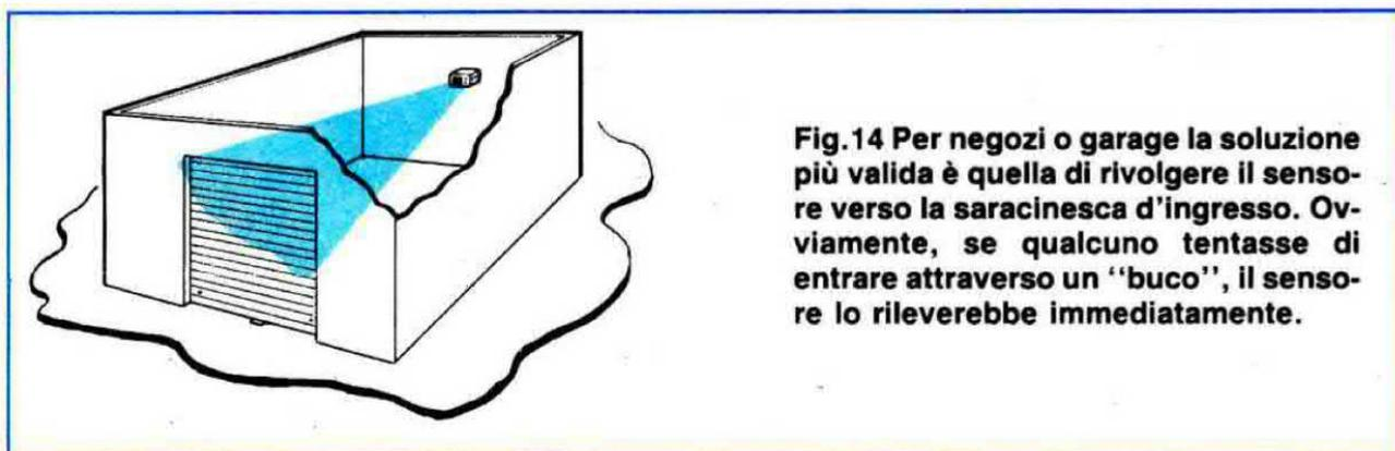
**Fig.14** Per negozi o garage la soluzione più valida è quella di rivolgere il sensore verso la saracinesca d'ingresso. Ovviamente, se qualcuno tentasse di entrare attraverso un "buco", il sensore lo rilevarebbe immediatamente.
