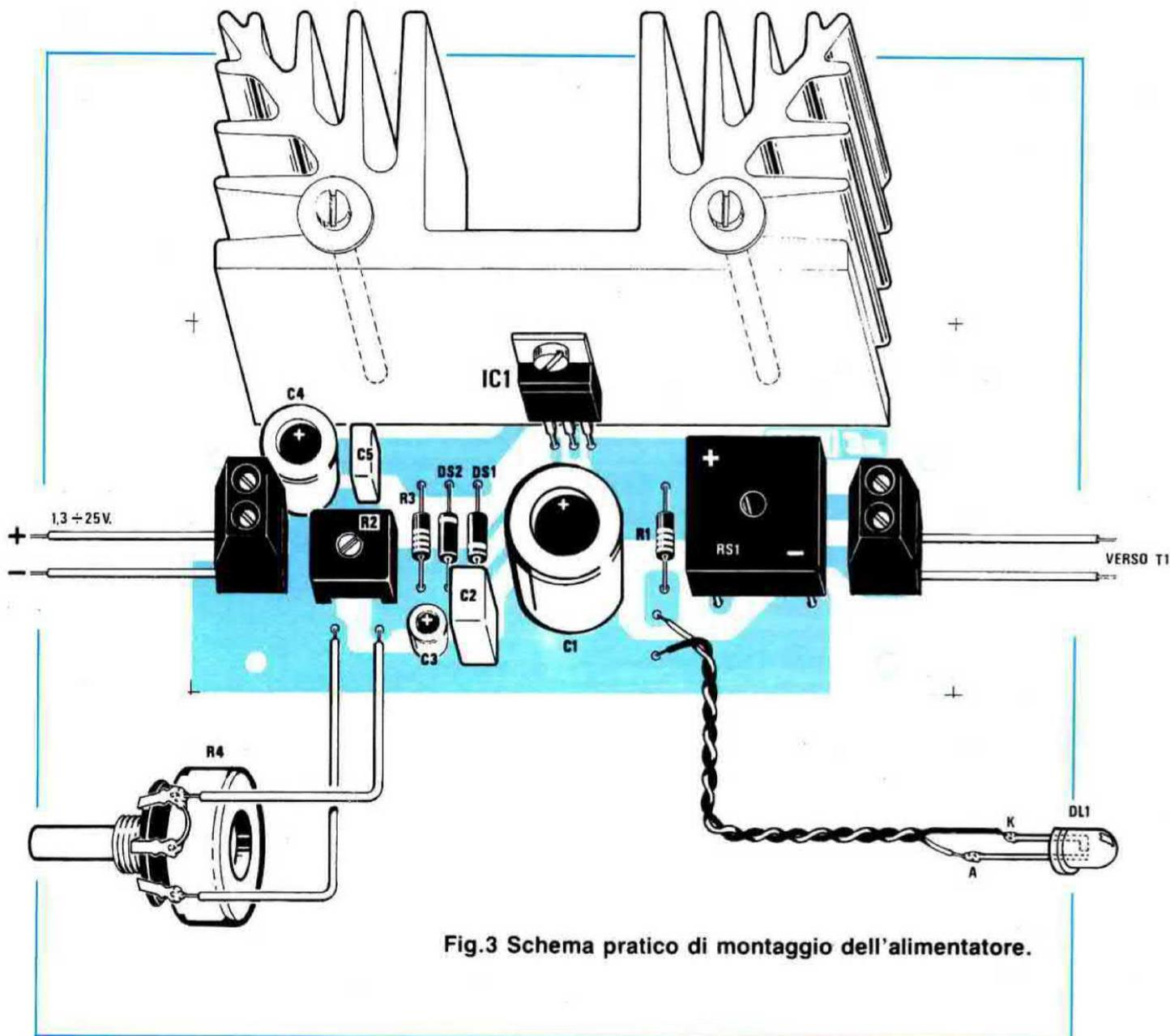
Fig.3 Schema pratico di montaggio dell'alimentatore.
