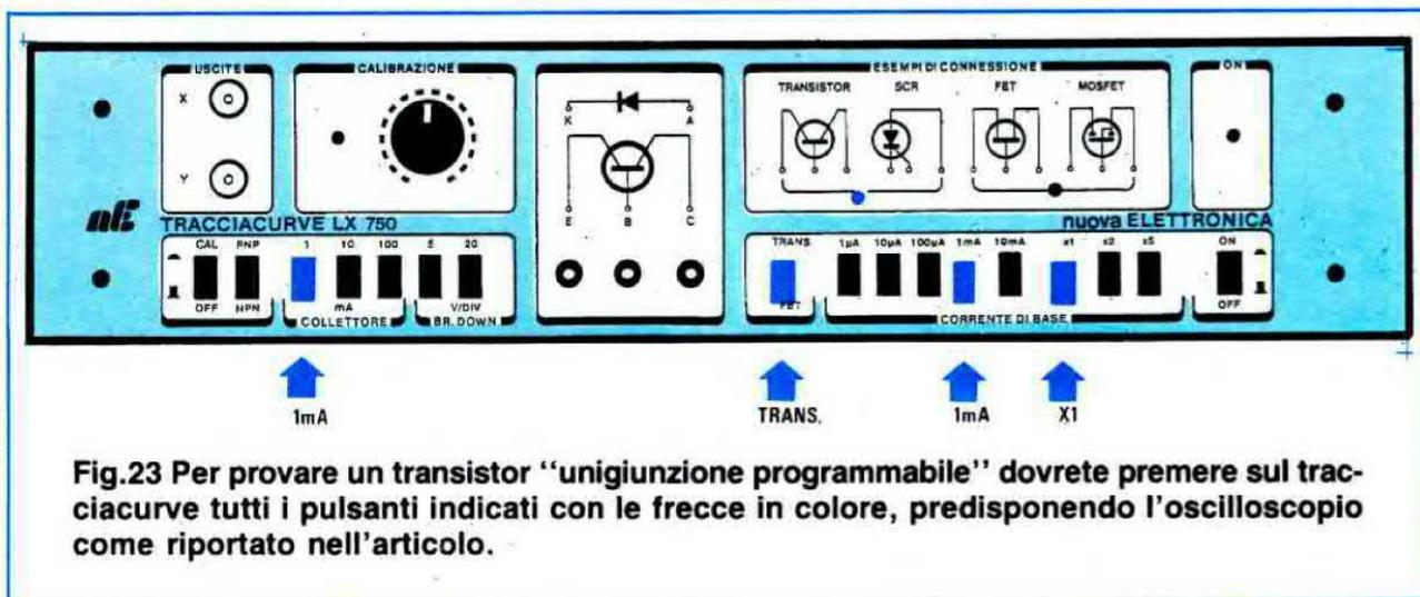
Fig.23 Per provare un transistor "unigiunzione programmabile" dovrete premere sul tracciacurve tutti i pulsanti indicati con le frecce in colore, predisponendo l'oscilloscopio come riportato nell'articolo.
