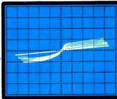
**Fig.21** Se vi apparirà una traccia come questa, avrete invertito il terminale **B1** con il terminale **B2**.
