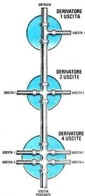
**Fig.107** Sulla colonna di discesa dovrete applicare degli altri raccordi (Derivatori), per prelevare l'acqua da portare a tutti i rubinetti presenti nell'appartamento. Un Derivatore dovrà sempre risultare "passante", perchè in ogni piano dello stabile occorrerà inserire altri Derivatori.
