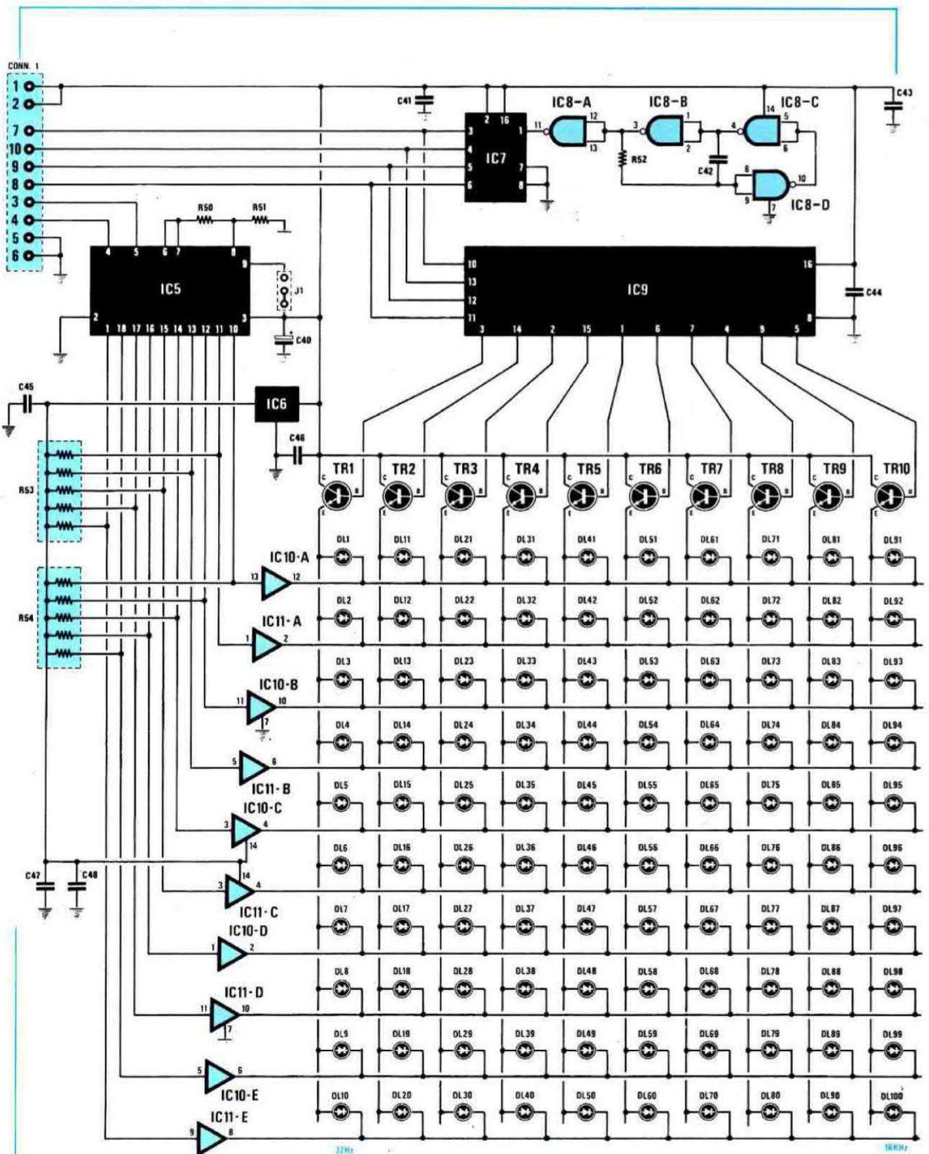
**Fig.3** Schema elettrico dello stadio di visualizzazione. Il connettore posto in alto a sinistra vi servirà per collegarvi con lo stadio dei filtri passa-banda riportato nella pagina precedente. Per la lista componenti vedere a pag. 101.
