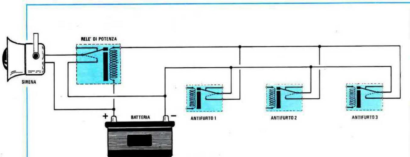
**Fig.11** Poichè in una casa può risultare necessario installare più sensori, tutte le uscite del relè dovranno essere collegate a una linea che provveda, tramite una batteria, ad eccitare un relè di potenza, che possa sopportare gli amper assorbiti dalla sirena di allarme.
