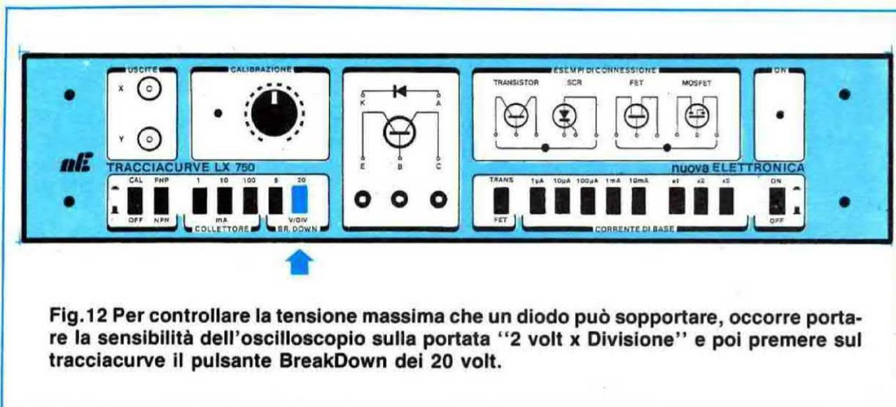
**Fig. 12** Per controllare la tensione massima che un diodo può sopportare, occorre portare la sensibilità dell'oscilloscopio sulla portata "2 volt x Divisione" e poi premere sul tracciacurve il pulsante BreakDown dei 20 volt.
