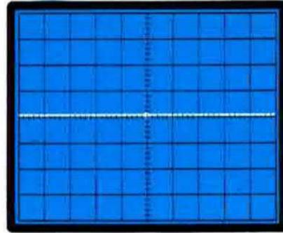
Fig.6 Prima di inserire il diodo nel tracciacurve, dovete cercare di far combaciare il "puntino luminoso" con il centro dello schermo dell'oscilloscopio.
