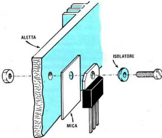
Fig.7 Poiché il terminale "E" dell'integrato uA.7905, risulta collegato al metallo del corpo, quando lo fissere-te sull'aletta destra del mobile (vedi foto sotto) dovreste isolarlo con una "mica" e "rondella isolante". Controllate, prima di collegare i ter-minali M-E-U al circuito stampato, che il corpo risulti perfettamente isolato dall'aletta di raffreddamento.
