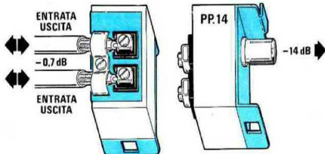
Fig.137 Per le prese tipo PP.14 il segnale d'ingresso e quello di proseguimento per la successiva presa, possono essere indifferentemente collegati sia al morsetto posto in alto che a quello posto in basso.
