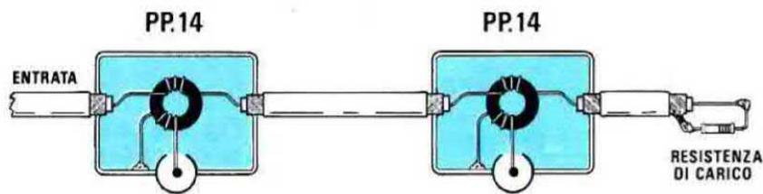
**Fig. 147** Poichè l'uscita "passante" dell'ultimo Derivatore (vedi fig.144) o di una Presa Passante rimarebbe aperta, condizione questa che potrebbe causare delle riflessioni sulle immagini, dovrete sempre ricordarvi di **CHIUDERLA** con un carico resistivo da 75 ohm. Se non troverete una simile resistenza, potrete utilizzare due resistenze da 150 ohm poste in parallelo.
