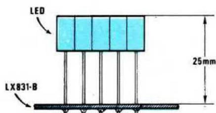
**Fig.10** I 100 diodi led che andranno fissati sul circuito stampato LX.831/B, dovranno essere collocati possibilmente ad una stessa altezza. Per ottenere questo livellamento vi consigliamo di inserire tutti i diodi senza saldarli e poi di rovesciare il circuito stampato tenendolo sollevato dal piano di circa 25 millimetri.
