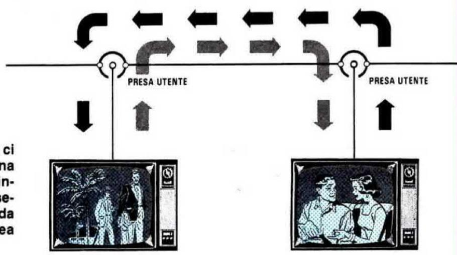
Fig.142 La stessa Presa ci deve altresì assicurare una elevata "attenuazione inversa", per evitare che i segnali di disturbo generati da una TV rientrino nella linea principale.
