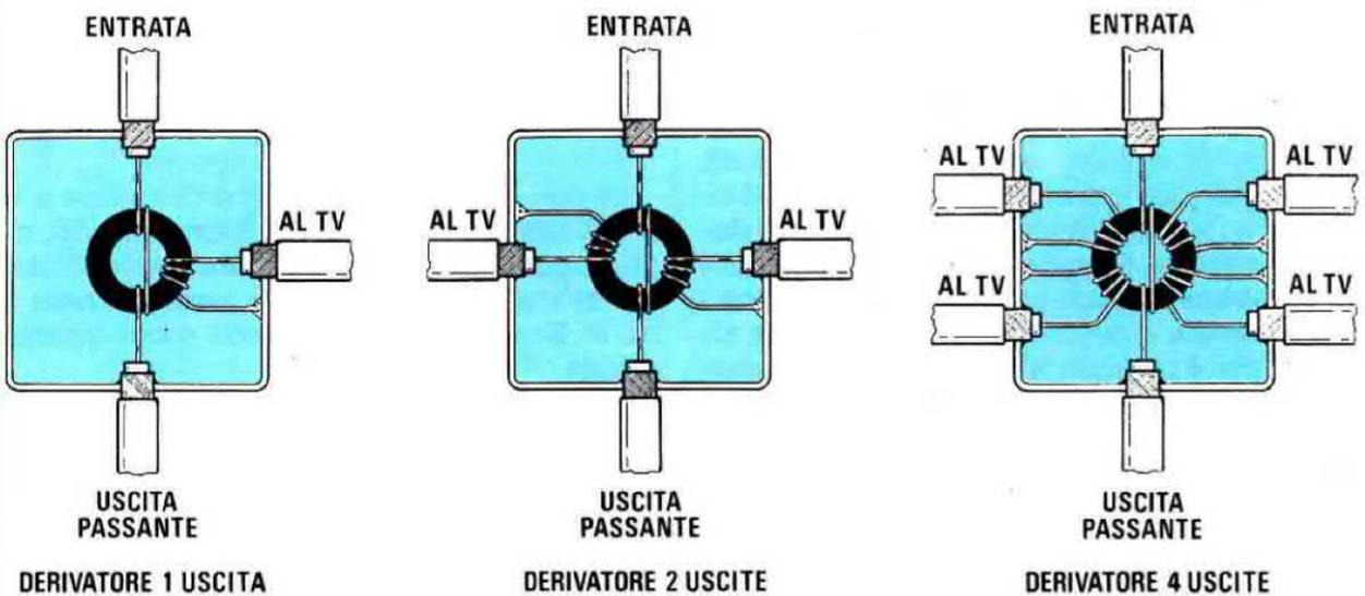
**Fig.118 I Derivatori "Induttivi"** sono i soli che dovreste scegliere per i vostri impianti, perchè la loro elevata attenuazione inversa impedisce che tutti i disturbi spurii si trasferiscano da un'uscita all'altra.
