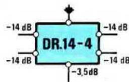
Derivatori con 1-2-4 uscite, tutte con attenuazioni di prelievo di - 14 dB.
