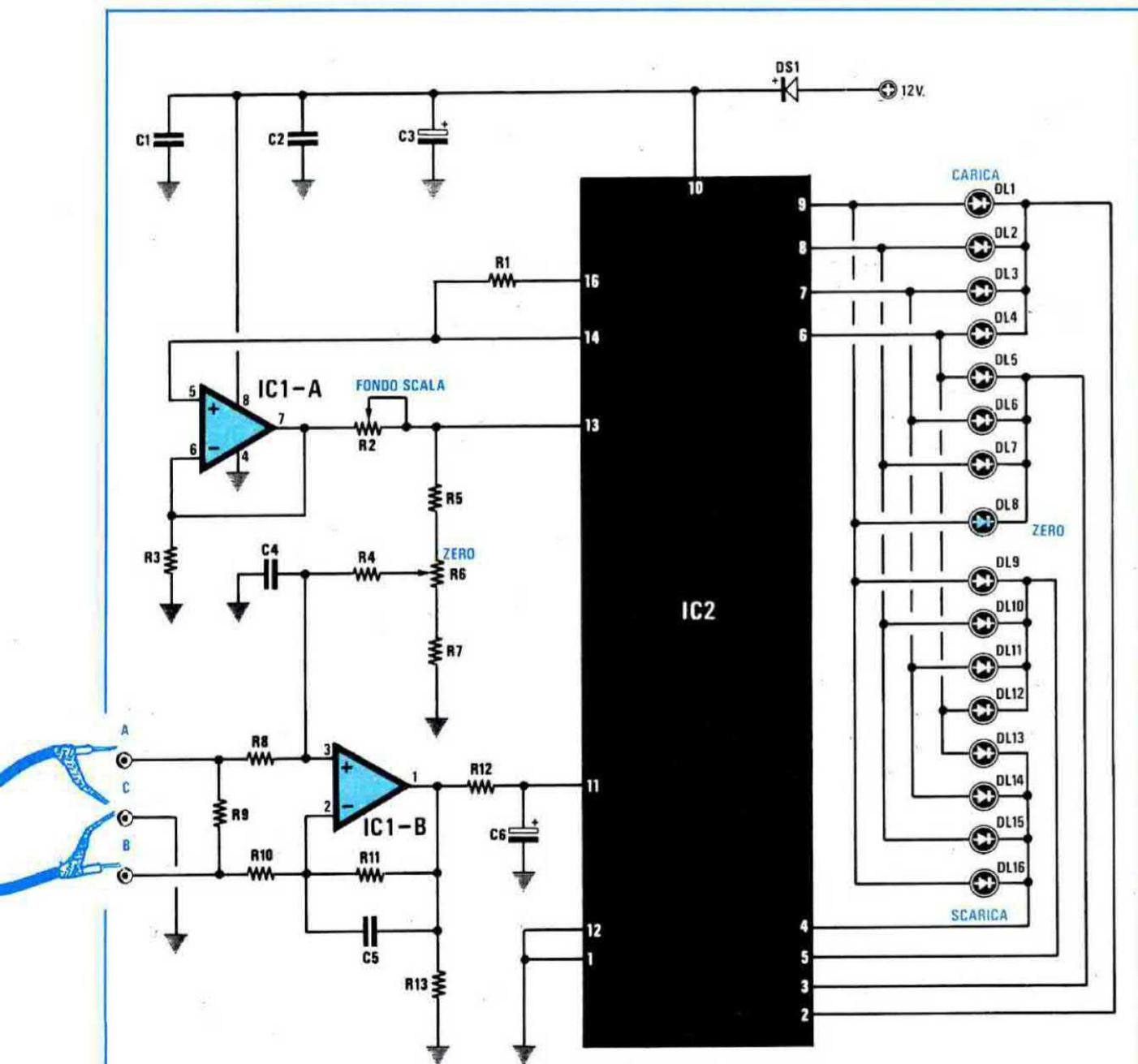
Fig.1 Schema elettrico dell'amperometro per auto. A sinistra sono visibili i due ingressi A - B che dovreste collegare alle estremità della piattina di massa della batteria.
