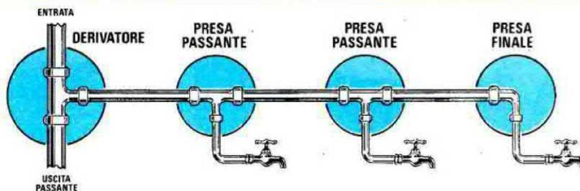
**Fig.108** Dal Derivatore partirà il tubo che porterà l'acqua a tutti i rubinetti. Se dal primo rubinetto dovrete proseguire ad un secondo, dovrete inserire un raccordo "passante", mentre per l'ultimo rubinetto dovrete necessariamente inserire un raccordo a L, poichè qui termina l'impianto.
