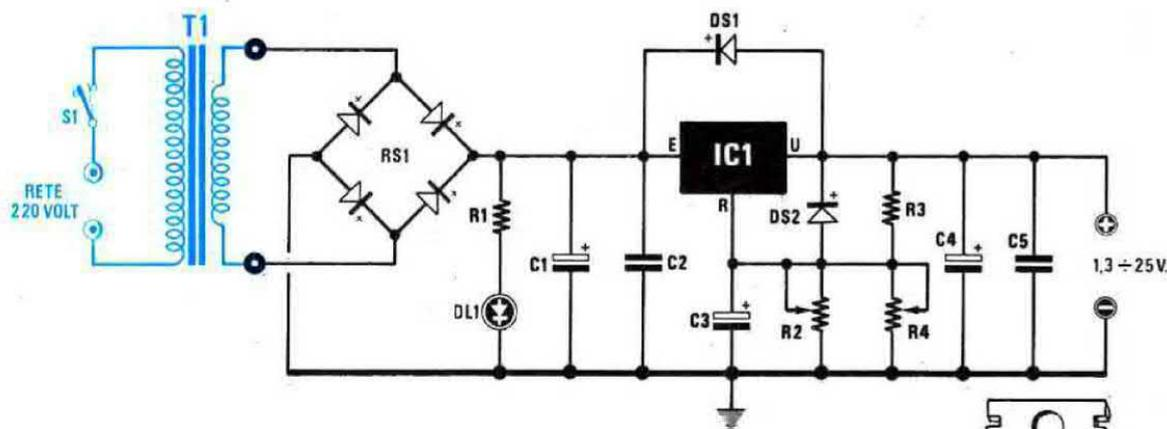
Fig.1 Schema elettrico dell'alimentatore e connessioni dell'LM.317.
