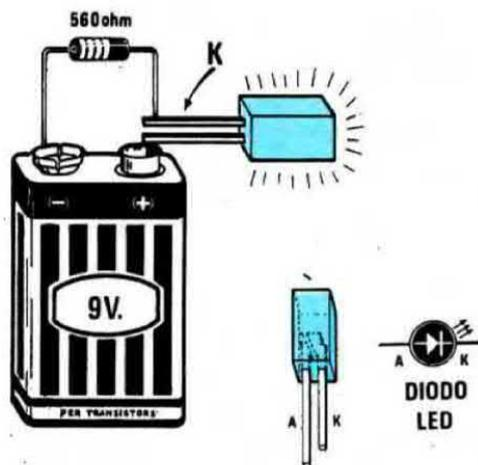
**Fig.9** Poichè ci siamo accorti che non sempre il terminale più corto di questi diodi led quadrati è il Catodo (K), prima di saldarli vi consigliamo di controllarli con una pila. Quando il diodo led si accenderà, potrete essere certi che il Catodo è il terminale che si trova rivolto verso il "negativo" della pila. A titolo informativo vi diciamo che abbiamo trovato quasi sempre invertiti i terminali dei soli diodi Verdi.
