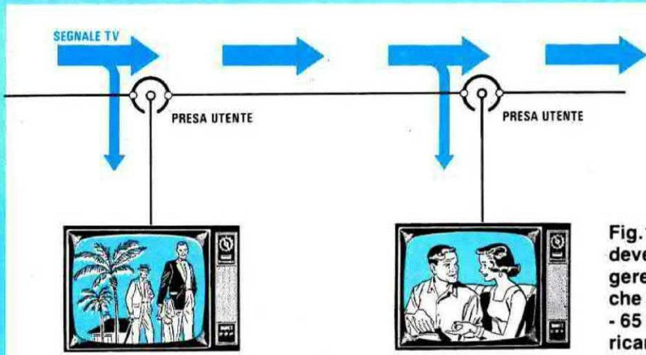
Fig.141 Una Presa utente ci deve permettere di far giungere sulle TV un segnale che risulti compreso tra i 58 - 65 dBmicrovolt, senza caricare la linea principale.
