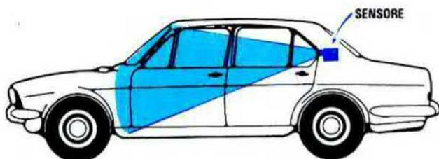
**Fig.8** Sarà bene collegare il sensore al piano del lunotto posteriore dell'auto, in modo da proteggere tutto l'interno dell'abitacolo. Come spiegato nell'articolo, il sensore si può separare dal resto del circuito.
