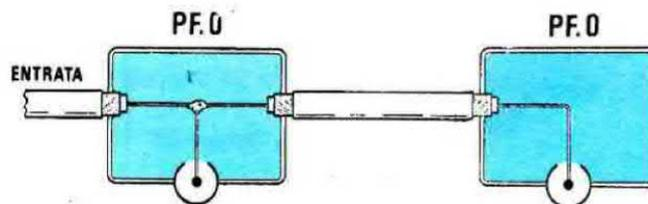
Fig.146 Sostituendo la prima presa con una PP.4,2 potrete collegare subito dopo questa una .PF.Ø, perchè i disturbi spurii presenti su una delle due prese non potranno mai passare da una presa all'altra.
