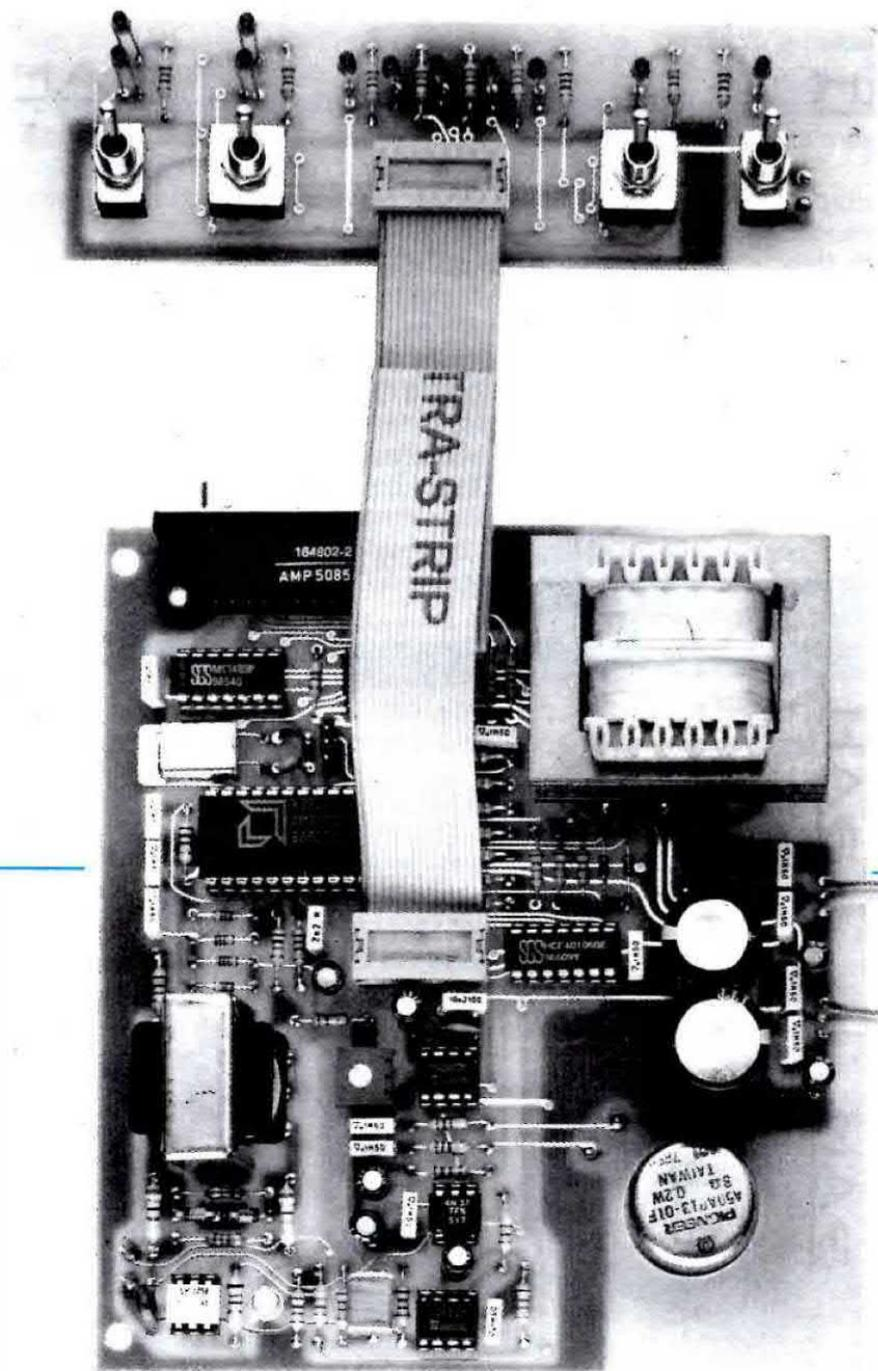
**Fig.4** In questa foto potete vedere come debbono essere innestati i due connettori della piastrina a 16 fili nei due circuiti stampati per non invertire le connessioni. Quando fisserete il circuito stampato LX.830/B sul pannello frontale del mobile, questa piastrina si posizionerà come vedesi in fig.7.
