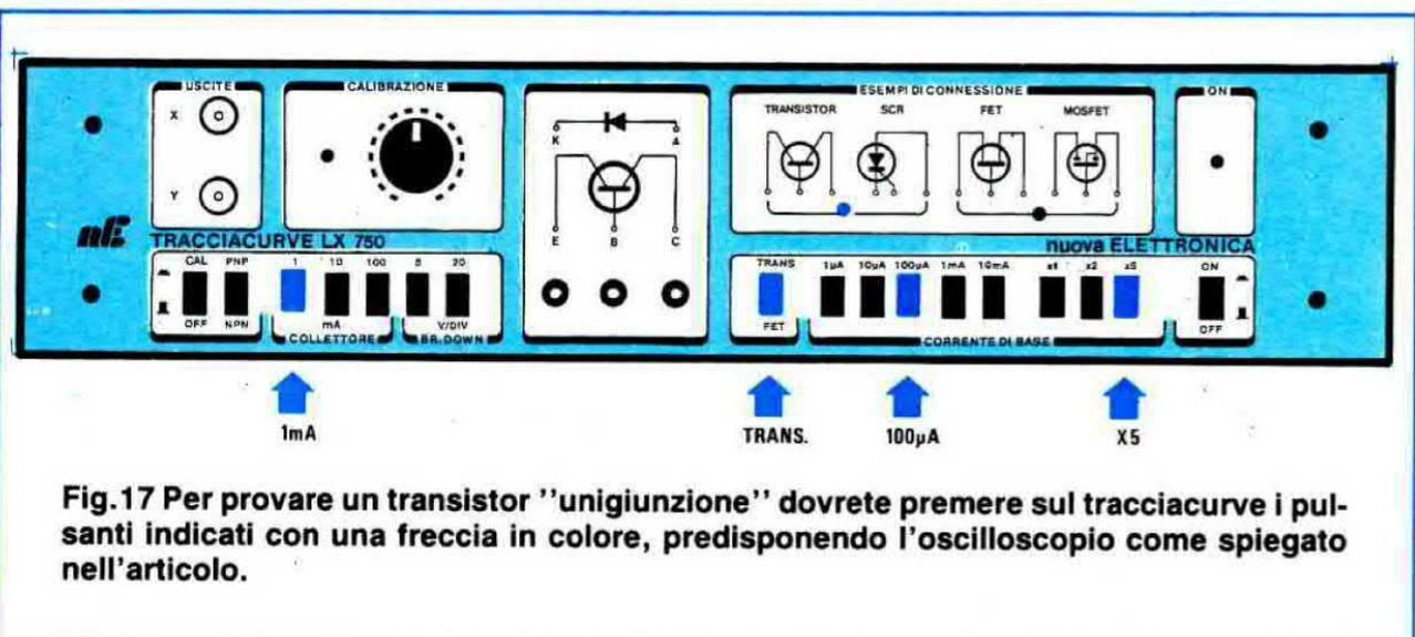
Fig.17 Per provare un transistor "unigiunzione" dovrete premere sul tracciacurve i pulsanti indicati con una freccia in colore, predisponendo l'oscilloscopio come spiegato nell'articolo.
