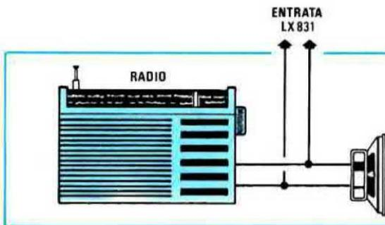
**Fig. 11** Per provare questo visualizzatore grafico sarà sufficiente collegare i due fili "Entrata BF" (vedi in fig.5 il cavetto posto a sinistra) ai due terminali di un altoparlante, oppure all'uscita cuffia di un qualsiasi ricevitore, registratore o preamplificatore Hi-Fi.
