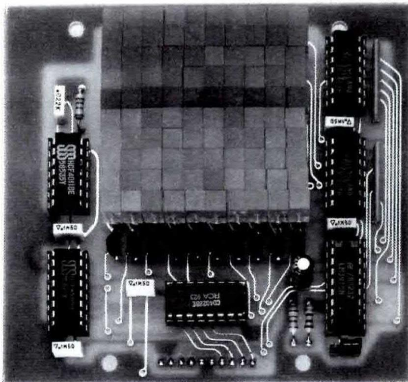
Fig.1 Con dieci colonne di diodi potrete visualizzare tutta la gamma delle frequenze acustiche e stabilire l'intensità del segnale per le diverse ottave. Nel prossimo numero vi insegneremo come trasformare questo circuito in fonometro per poter così equalizzare un ambiente.
