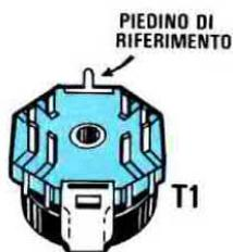
**Fig.6** Il piedino di riferimento, come vedesi in questo disegno, è un piccolo terminale collegato allo schermo metallico dello stesso trasformatore.
