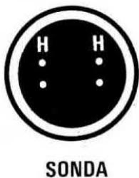
**Fig.7** Cercate di non sbagliarvi nel collegare i quattro terminali che fuoriescono dalla sonda. I due terminali del filamento sono contrassegnati con la lettera H.
