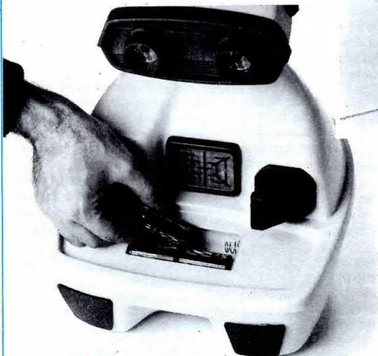
**Fig.23** Inserito nel vano visibile in questa foto il portapile, collocate al suo interno le quattro pile a torcia da 1,5 volt, rispettando la loro polarità positiva e negativa.
