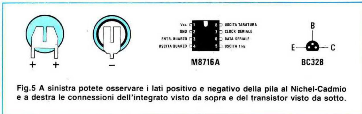
Fig.5 A sinistra potete osservare i lati positivo e negativo della pila al Nichel-Cadmio e a destra le connessioni dell'integrato visto da sopra e del transistor visto da sotto.
