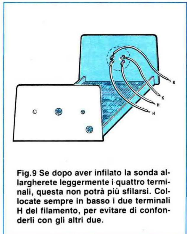
**Fig.9** Se dopo aver infilato la sonda allargherete leggermente i quattro terminali, questa non potrà più sfilarsi. Collocate sempre in basso i due terminali H del filamento, per evitare di confonderli con gli altri due.
