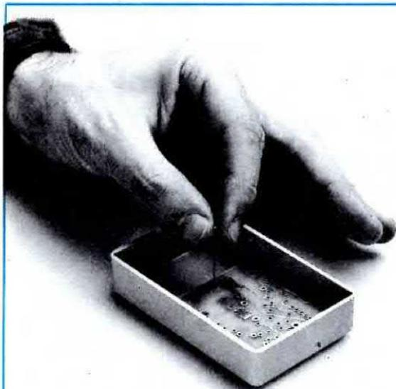
**Fig.13** Fissato il circuito stampato ancora vergine all'interno del mobiletto, infilate nei fori dei quattro pulsanti un ago e cercate di incidere la plastica del coperchio.
