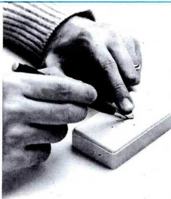
**Fig.14** Forate con una punta da 2 mm. i punti incisi, poi infilate il pulsante cercando di fare entrare i terminali nel circuito stampato. Con una matita disegnate il perimetro.
