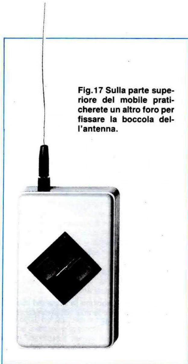
**Fig.17** Sulla parte superiore del mobile praticerete un altro foro per fissare la boccola dell'antenna.
