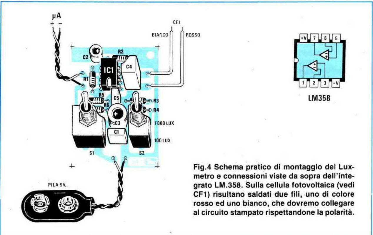
Fig.4 Schema pratico di montaggio del Luxmetro e connessioni viste da sopra dell'integrato LM.358. Sulla cellula fotovoltaica (vedi CF1) risultano saldati due fili, uno di colore rosso ed uno bianco, che dovremo collegare al circuito stampato rispettandone la polarità.
