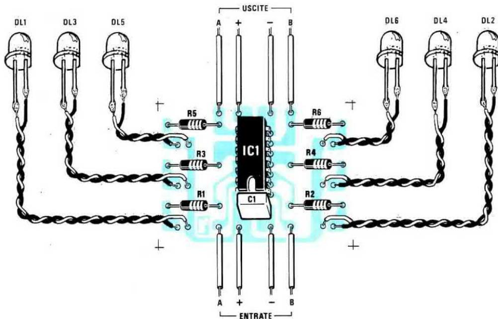
**Fig.8** Schema pratico di montaggio del circuito LX.866. I quattro fili posti in basso, siglati "entrate" A + - B, andranno necessariamente collegati ai corrispondenti fili posti sull'uscita dello schema di fig.7. Gli stessi fili "uscita" presenti in questo circuito serviranno per collegare altri circuiti LX.866.
