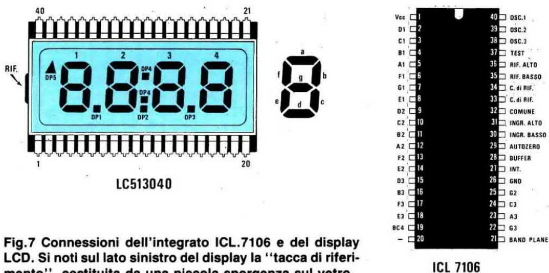
**Fig.7 Connessioni dell'integrato ICL.7106 e del display LCD. Si noti sul lato sinistro del display la "tacca di riferimento", costituita da una piccola sporgenza sul vetro.**
