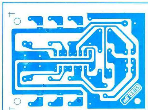
Fig.5 Tutti i componenti richiesti per la realizzazione del progetto LX.865 (vedi fig.3), andranno montati su questo circuito stampato monofaccia, qui riprodotto a grandezza naturale.
