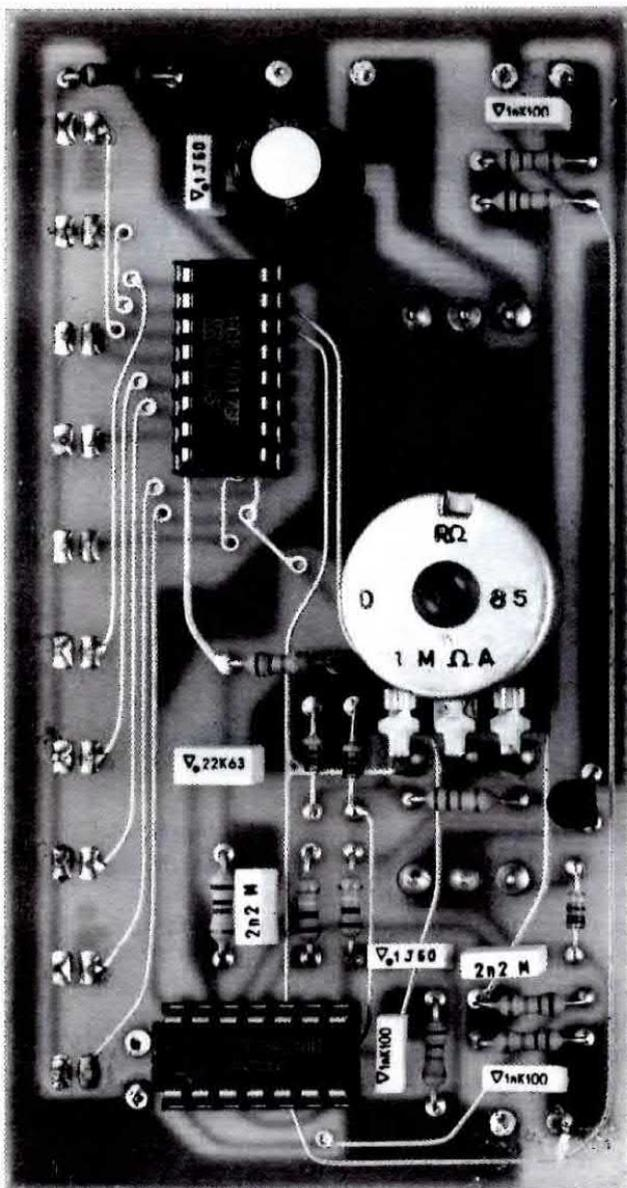
**Fig.5** Il circuito stampato, come si può notare in questa foto ed in quella di fig.3, è un doppia faccia con fori metallizzati. Sulle piste dello stampato che vi forniremo è depositata una vernice protettiva di colore verde, che lascia scoperti i soli punti da saldare. In questo circuito abbiamo inserito per C3 una capacità di 100.000 pF, per aumentare la velocità di scorrimento dei diodi led. In pratica, la capacità più idonea per questa funzione rimane confermata sui 220.000 pF.
