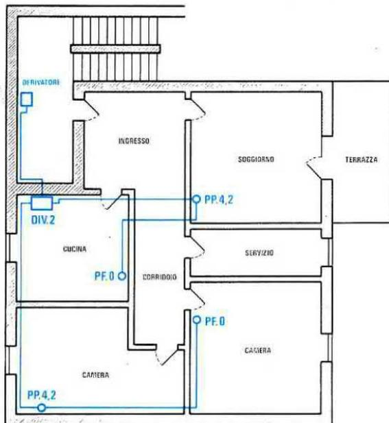
**Fig.197** Come vedesi in figura, l'uscita del Derivatore anziché congiungersi con le prese utente, verrà collegata all'ingresso del Divisore DIV.2. Sull'uscita di questo Divisore verranno collegate le due linee di diramazione, che dovranno congiungersi alla prima presa passante PP.4,2, per poi proseguire per la finale PF.0. Per chi volesse solo tre prese, sarà sufficiente sostituire la finale PF.0 con una passante PP.4,2.
