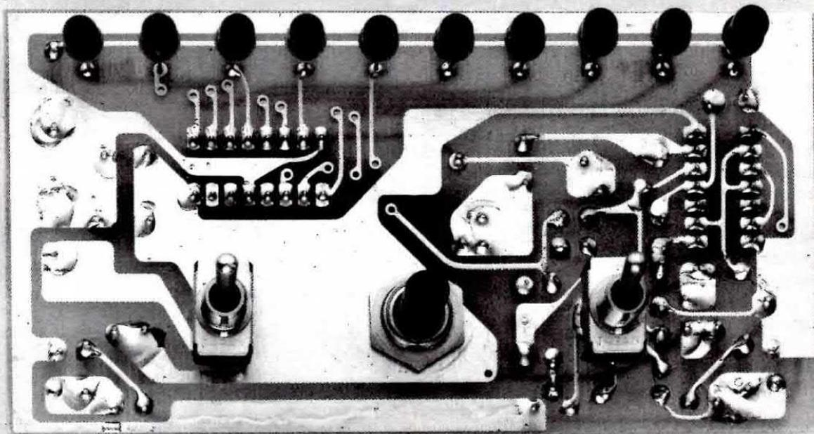
**Fig.3** Foto del circuito stampato visto dal lato in cui dovreste inserire i dieci diodi led. In questo stesso lato inserirete anche i due deviatori a levetta, saldandone dal lato opposto i tre terminali.
