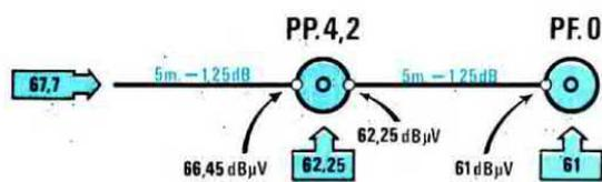
**Fig.201** Anche se una linea di 10 metri con inserita una presa PP.4,2 ed una finale PF.0 richiede un segnale di "67,7 dBmicrovolt", applicandole solo "67,3 dBmicrovolt" (vedi fig.200), non scenderemo mai sotto il valore minimo consigliato.
