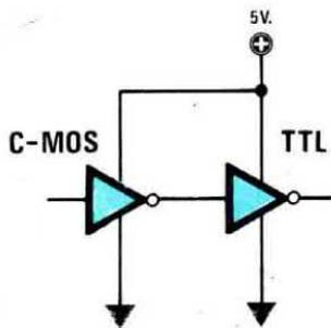
**Fig.3** Non risultando compatibili i livelli logici di un C/Mos con quelli di un TTL, volendo collegare l'uscita di un C/Mos ad un ingresso TTL, la soluzione più semplice è quella di alimentare il C/Mos con la stessa tensione dei 5 volt utilizzata per il TTL.
