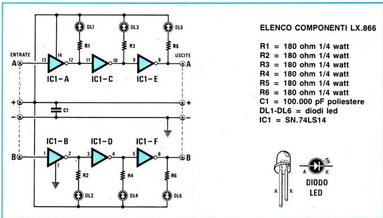
**Fig.4** Schema elettrico del circuito LX.866. Questo circuito supplementare se collegato all'uscita del circuito LX.865 (vedi terminali A + - B), permetterà di accendere altri 6 diodi led. Sull'uscita di questo LX.866 (vedi terminali A + - B posti a destra), potremo collegare in parallelo altri circuiti LX.866.
