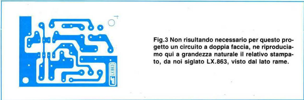
Fig.3 Non risultando necessario per questo progetto un circuito a doppia faccia, ne riproduciamo qui a grandezza naturale il relativo stampato, da noi siglato LX.863, visto dal lato rame.
