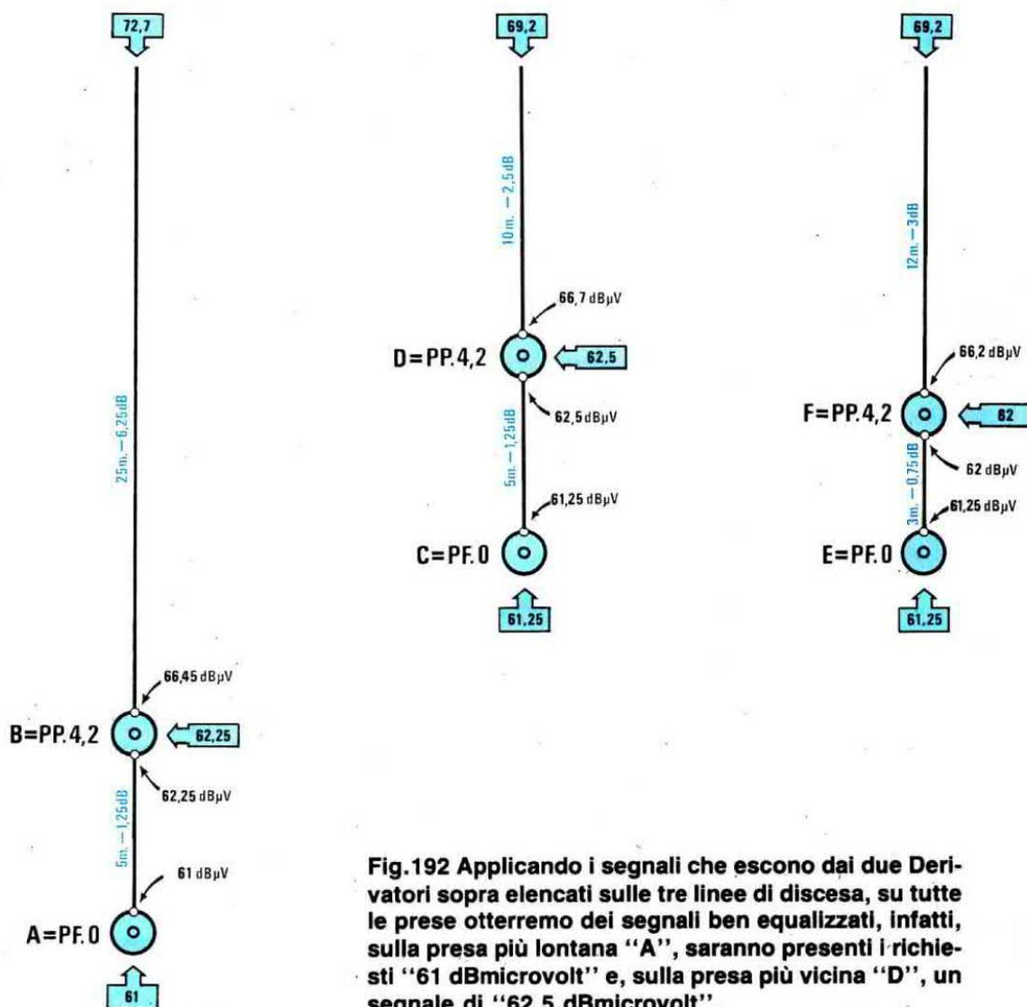
Fig.192 Applicando i segnali che escono dai due Derivatori sopra elencati sulle tre linee di discesa, su tutte le prese otterremo dei segnali ben equalizzati, infatti, sulla presa più lontana "A", saranno presenti i richiesti "61 dBmicrovolt" e, sulla presa più vicina "D", un segnale di "62,5 dBmicrovolt".
