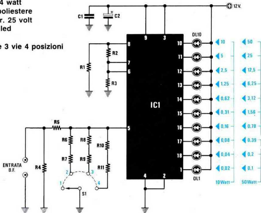
Questo progetto vi permetterà di realizzare un semplice wattmetro BF, in grado di misurare il livello di uscita di una qualsiasi radio o amplificatore. Il circuito, progettato per 10 e 50 watt massimi, può essere modificato anche per misurare potenze maggiori su impedenze di carico da 4 o 8 ohm.
