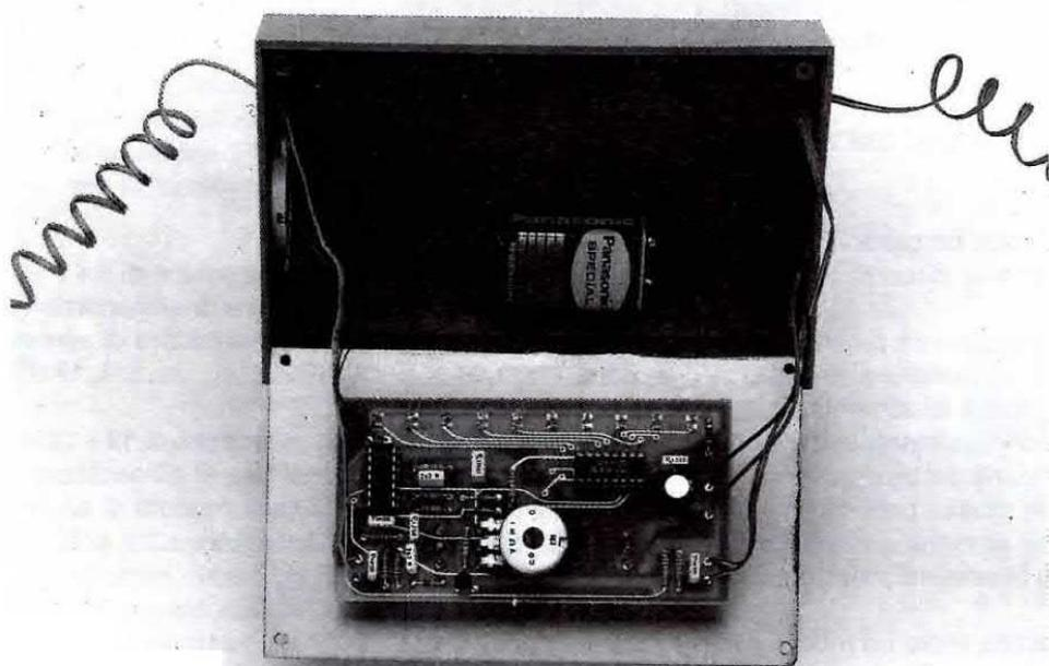
Il circuito andrà fissato sul pannello frontale del mobile plastico, collocando nello spazio interno la pila e la cicalina. Come vedesi nella foto di destra, i due pulsanti andranno fissati su due supporti cilindrici.
