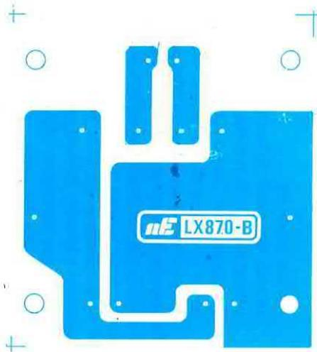
Fig.10 Disegno a grandezza naturale del circuito stampato LX.870/B, utile per realizzare lo stadio di alimentazione per questo automatico. Tutti gli stampati che noi forniamo sono in fibra di vetro, completi di fori e di disegno serigrafico con le relative sigle dei componenti.
