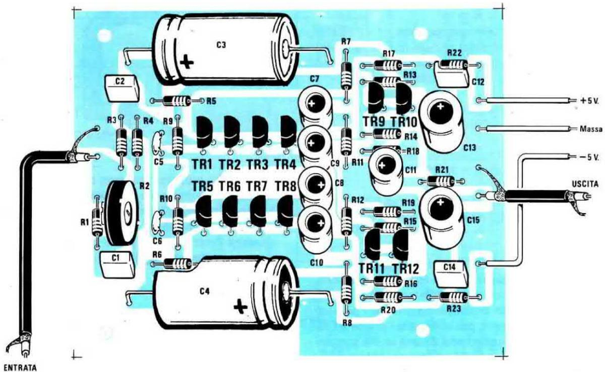
Fig.6 Schema pratico di montaggio del preamplificatore per bobina mobile. Questo circuito dovrà risultare totalmente schermato, quindi una volta costruito dovreste necessariamente racchiuderlo entro un piccolo mobile metallico, per evitare che capti del ronzio di alternata. Per i collegamenti dei cavetti di entrata e di uscita leggete attentamente l'articolo.
