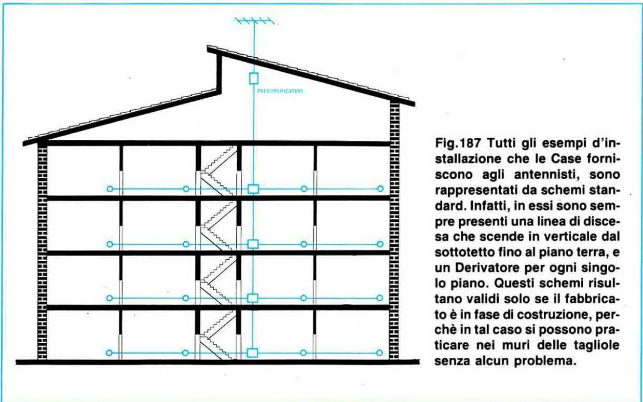
**Fig.187** Tutti gli esempi d'installazione che le Case forniscono agli antenisti, sono rappresentati da schemi standard. Infatti, in essi sono sempre presenti una linea di discesa che scende in verticale dal sottotetto fino al piano terra, e un Derivatore per ogni singolo piano. Questi schemi risultano validi solo se il fabbricato è in fase di costruzione, perchè in tal caso si possono praticare nei muri delle tagliole senza alcun problema.
