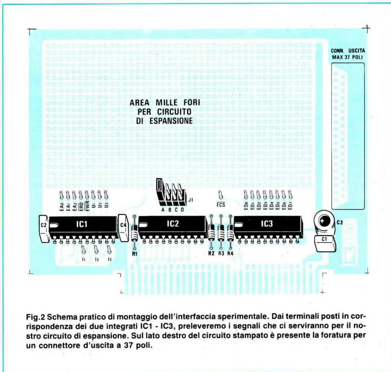
**Fig.2 Schema pratico di montaggio dell'interfaccia sperimentale. Dai terminali posti in corrispondenza dei due integrati IC1 - IC3, preleveremo i segnali che ci serviranno per il nostro circuito di espansione. Sul lato destro del circuito stampato è presente la foratura per un connettore d'uscita a 37 poli.**
