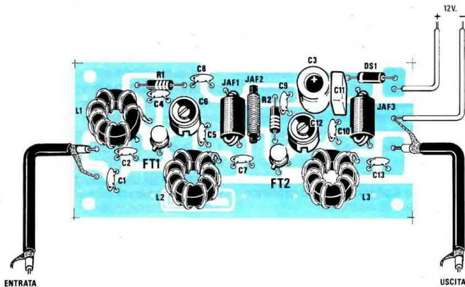
**Fig.4** Schema pratico di montaggio del preamplificatore. Come spiegato nell'articolo, sulla prima spira delle bobine L2 e L3 dovrete saldare un sottile filo, per poterlo poi collegare alla pista del condensatore C7 e C13.
