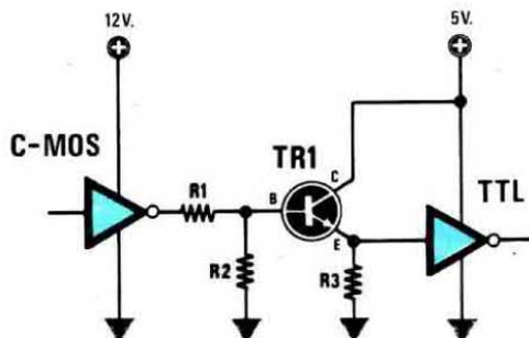
**Fig.5** Se non fosse possibile alimentare il C/Mos a 5 volt, dovremmo necessariamente realizzare una piccola interfaccia, utilizzando un transistor NPN tipo 2N2222 o similare.
