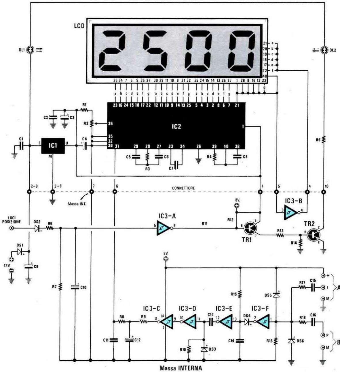
Fig.6 Schema elettrico del comparatore, del voltmetro digitale con display LCD e connessioni degli integrati. L'ingresso "B" serve solo per motori a benzina.
