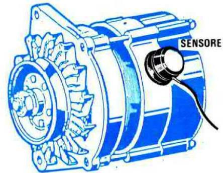
Un sistema più valido consiste nell'utilizzare una piccola fascetta metallica che possa stringere il captatore sul corpo dell'alternatore, oppure tentare di incollare la ventosa con del silicone o altro collante che possa resistere con il passare del tempo.
