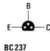
Fig.2 Connessioni interne dei due integrati CD.4017 e CD.4093 viste da sopra (si noti a sinistra la tacca di riferimento), e connessioni EBC del transistor BC.237, viste invece da sotto.
