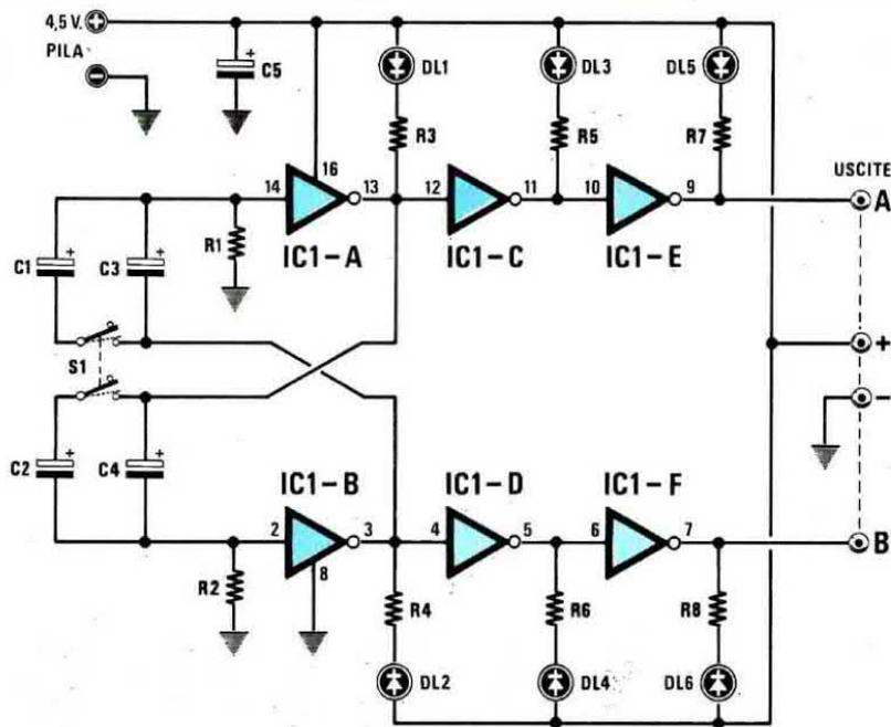
Fig.3 Schema elettrico del circuito base LX.865, necessario per accendere, alternativamente, fino ad un massimo di 6 diodi led. Le quattro boccole presenti sul lato sinistro, siglate "A + - B", serviranno per far giungere al circuito LX.866 i necessari livelli logici e la tensione di alimentazione.
