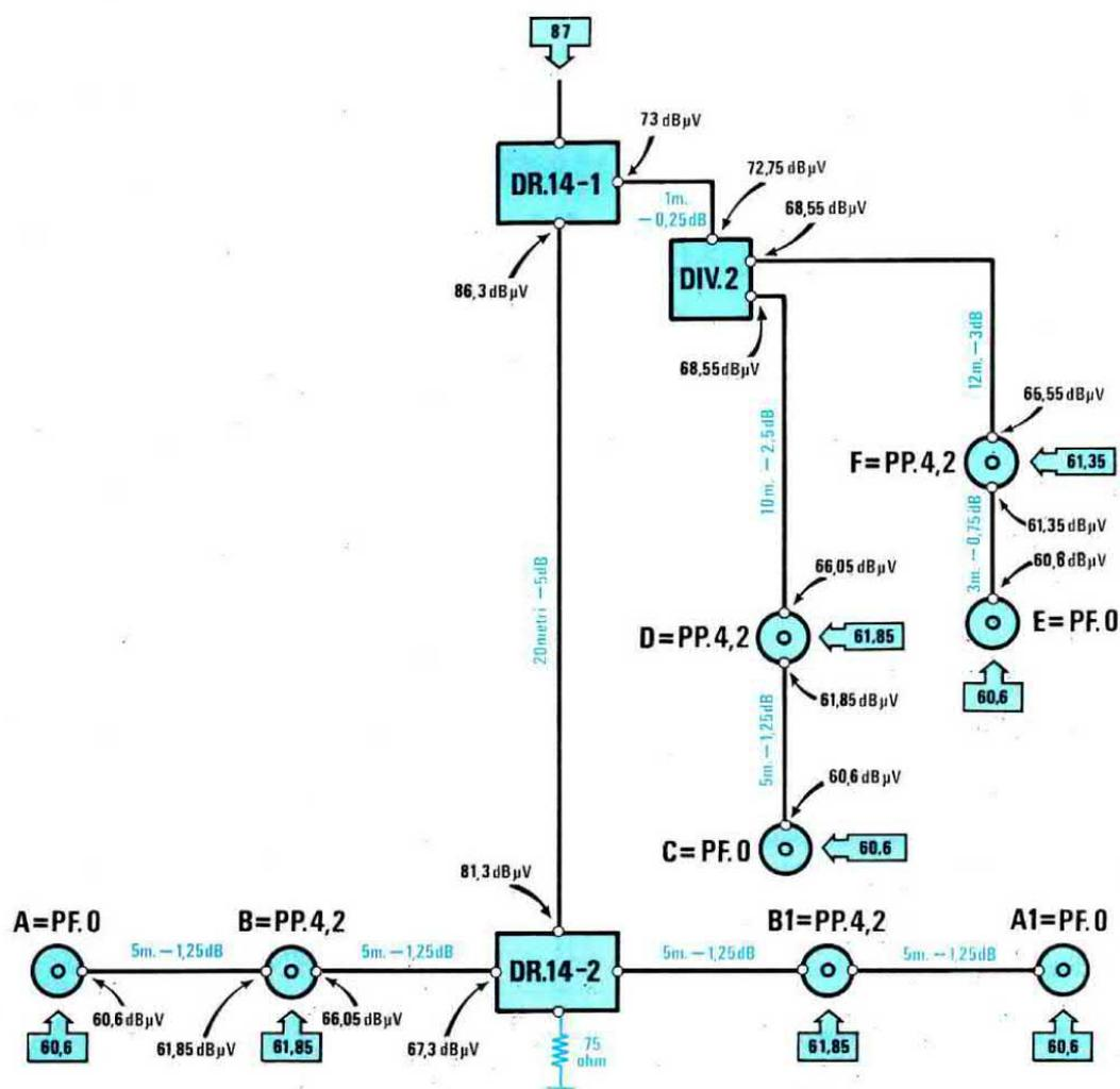
**Fig.200** Negli impianti considerati in precedenza, è assolutamente necessario che l'amplificatore d'antenna sia in grado di erogare "4-5 dB" in più del richiesto. Se ciò non fosse possibile, dovremmo cercare una diversa soluzione per assicurare ad ogni presa un segnale che non risulti mai inferiore a "58 dBmicrovolt". Lo schema qui sopra riportato può risolvere questo problema. Si noti sull'ultimo Derivatore la resistenza di carico da 75 ohm.
