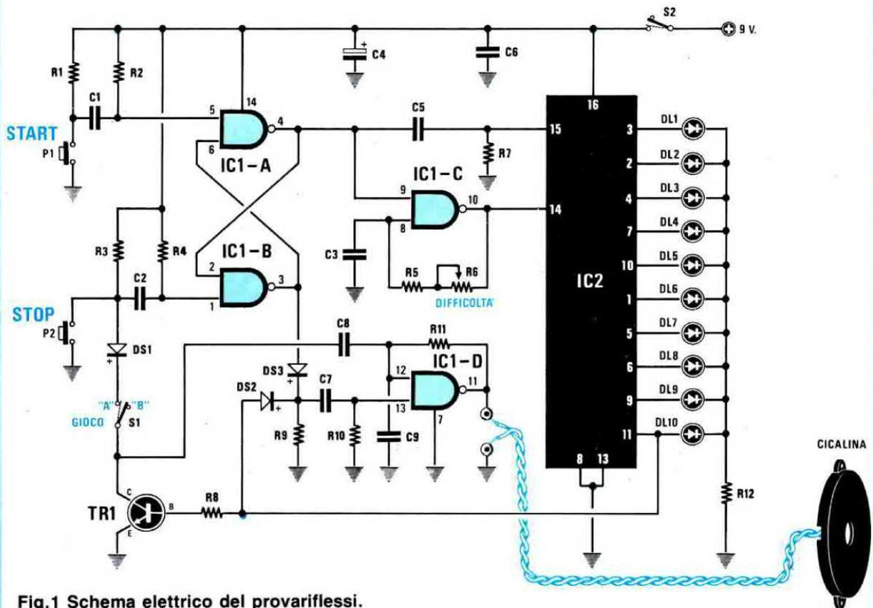
Fig.1 Schema elettrico del provariflessi.
