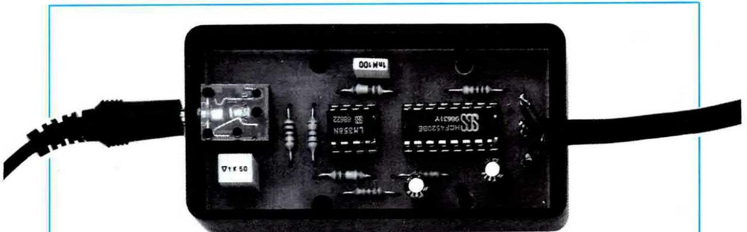
**Fig.5** Il circuito del captatore magnetico visibile in fig.2, verrà racchiuso entro un altro piccolo mobile plastico. Sul lato sinistro della foto possiamo vedere la presa femmina in cui innesteremo il jack del captatore telefonico. Questo captatore, come spiegato nell'articolo, serve solo per i motori Diesel.
