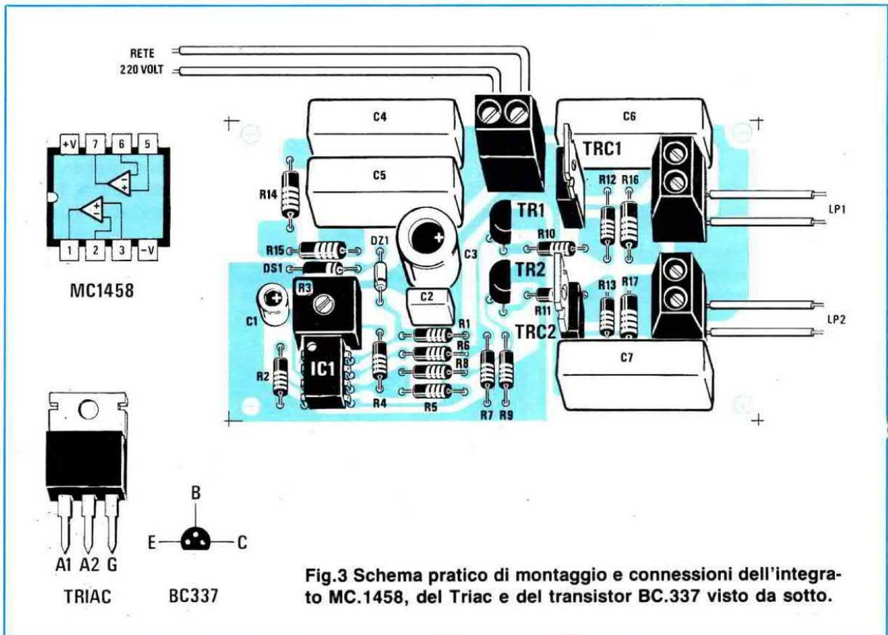
Fig.3 Schema pratico di montaggio e connessioni dell'integrato MC.1458, del Triac e del transistor BC.337 visto da sotto.
