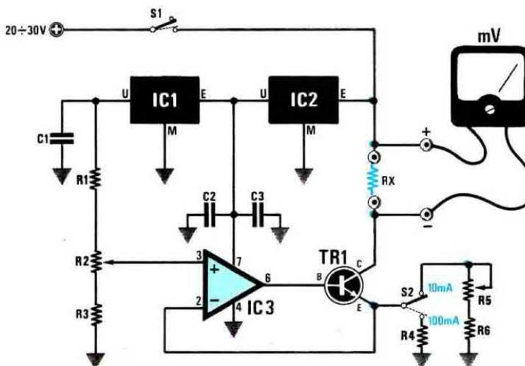
mente costante, selezionabile tramite il deviatore S2 in due valori fondo-scala: 10 e 100 milliamper. Applicando un millivoltmetro o un tester digitale posto sulla portata di 200 millivolt, ai capi della resistenza incognita RX si potrà leggere una tensione proporzionale al suo valore ohmmico.
