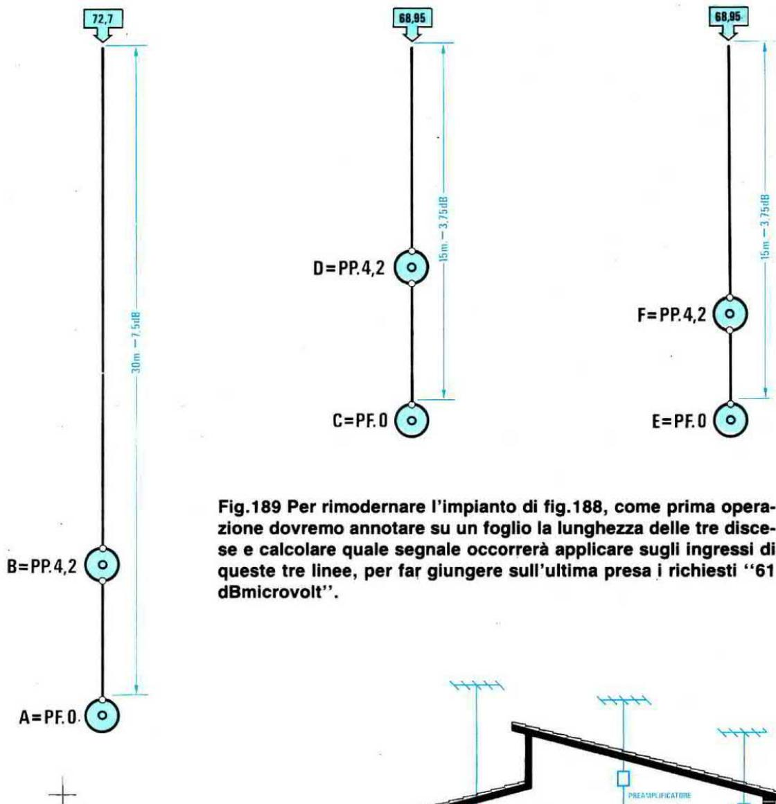
Fig.189 Per rimodernare l'impianto di fig.188, come prima operazione dovremo annotare su un foglio la lunghezza delle tre discese e calcolare quale segnale occorrerà applicare sugli ingressi di queste tre linee, per far giungere sull'ultima presa i richiesti "61 dBmicrovolt".
