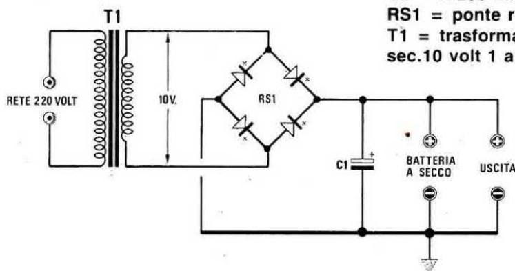
Fig.4 Schema dell'alimentatore da utilizzare per l'automatismo descritto in questo articolo. In tale circuito potremo collegare in tampone una "batteria a secco". **NOTA BENE: non inserire pile normali, nè al nichel-cadmio.**
