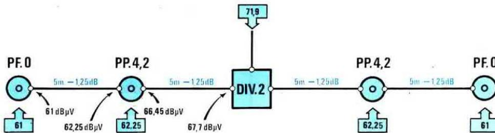
**Fig.196** Aggiungere in un appartamento più prese utente, è possibile solo se l'amplificatore d'antenna è in grado di erogare "4-5 dB" in più rispetto a quelli calcolati in precedenza, per compensare l'attenuazione del Divisore DIV.2 che ora bisognerà aggiungere.
