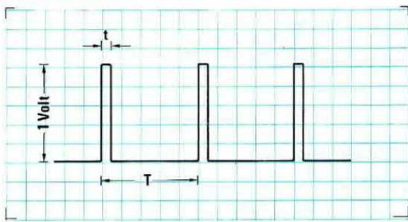
**Fig.3** L'operazionale IC1/B (vedi fig.2) trasformerà il segnale sinusoidale captato dall'alternatore in impulsi digitali di ampiezza costante. Al variare del numero di giri, aumenterà solo il numero degli impulsi nel tempo "T".
