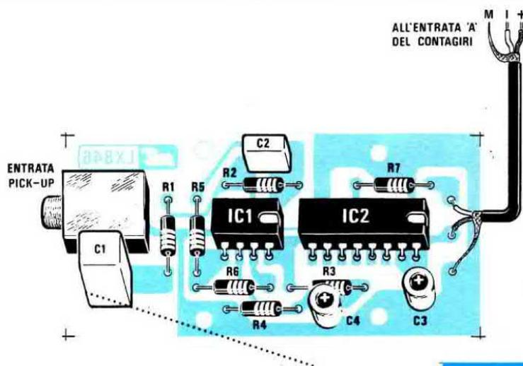
Fig.8 Schema pratico di montaggio del captatore magnetico. I tre fili M,I, + andranno collegati all'ingresso "A", come vedesi in fig.6.
