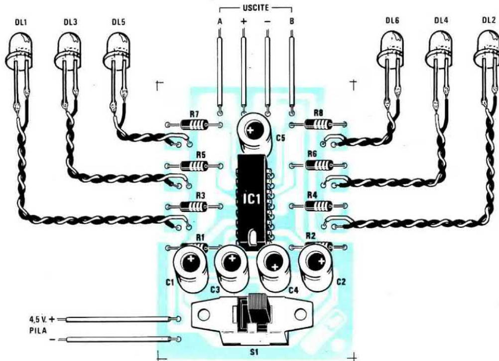
**Fig.7** Schema pratico di montaggio del circuito LX.865. I terminali del commutatore a slitta S1 potranno essere saldati direttamente sul circuito stampato o collegati allo stesso con dei fili volanti. Nel collegare i diodi led allo stampato, cercate di non invertire il terminale più lungo con quello più corto.
