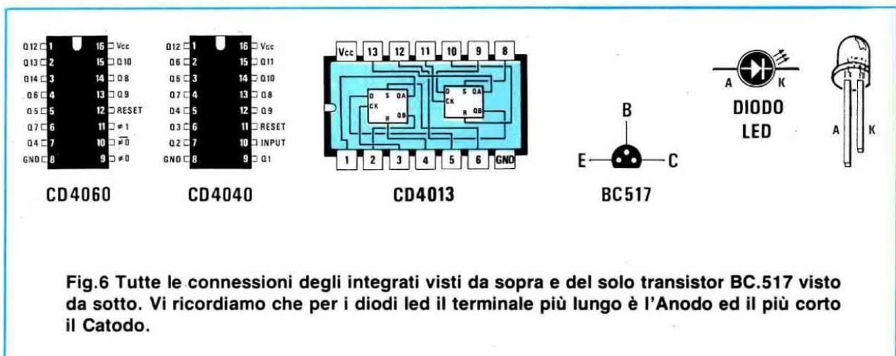
Fig.6 Tutte le connessioni degli integrati visti da sopra e del solo transistor BC.517 visto da sotto. Vi ricordiamo che per i diodi led il terminale più lungo è l'Anodo ed il più corto il Catodo.
