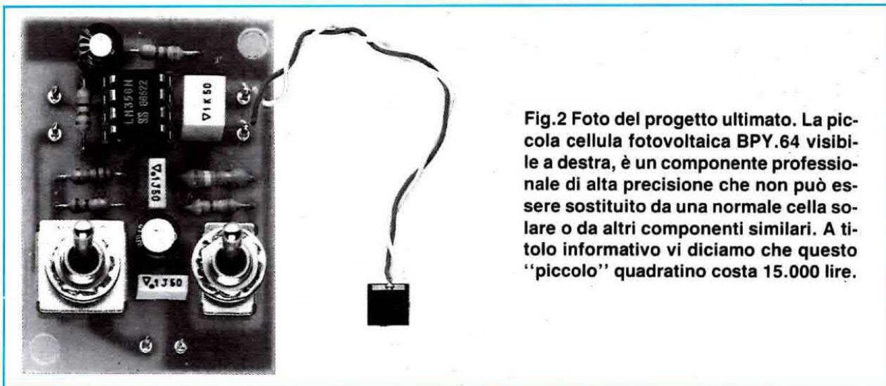
Fig.2 Foto del progetto ultimato. La piccola cellula fotovoltaica BPY.64 visibile a destra, è un componente professionale di alta precisione che non può essere sostituito da una normale cella solare o da altri componenti similari. A titolo informativo vi diciamo che questo "piccolo" quadratino costa 15.000 lire.
