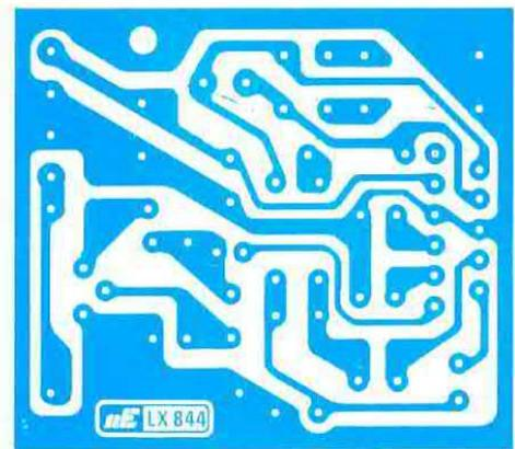
Fig.5 Essendo riusciti a realizzare un circuito stampato monofaccia, possiamo qui presentarvi, a grandezza naturale, il disegno del circuito stampato LX.844 visto dal lato rame.
