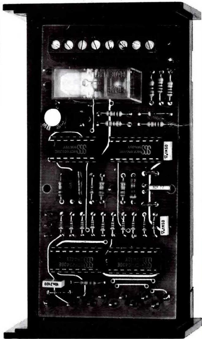
Fig.9 Terminato il montaggio il circuito andrà fissato all'interno del mobile plastico. Sul coperchio di questo stesso mobile andranno collocati il commutatore rotativo, il diodo led e i due deviatori a levetta. Si noti sul lato destro la morsettiera per collegare i fili di alimentazione e per l'uscita del relè.
