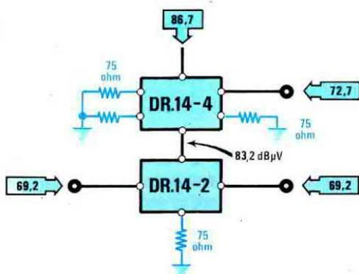
Fig.191 Per utilizzare le tre linee di discesa preesistenti, visibili in fig.188, potremo applicare nel sottotetto un Derivatore DR.14/4 ed un Derivatore DR.14/2. Dal primo Derivatore preleveremo il segnale per la discesa B-A e dal secondo Derivatore i segnali per le discesa D-C e F-E.
