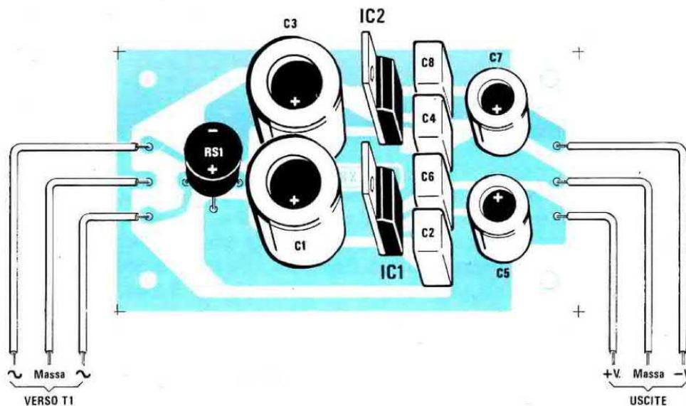
**Fig.4** Schema pratico di montaggio dell'alimentatore. Sui tre fili di sinistra collegheremo il secondario del trasformatore T1, mentre dai tre fili di destra preleveremo la tensione stabilizzata.
