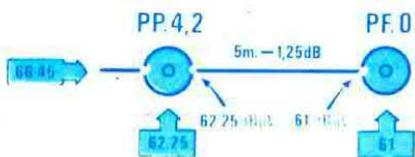
**Fig.190 Ricordatevi, che per far giungere ad una presa finale PF0 un segnale di "61 dBmicrovolt", è necessario che sull'ingresso della presa passante PP.4,2 giungano almeno "66,45 dBmicrovolt".**
