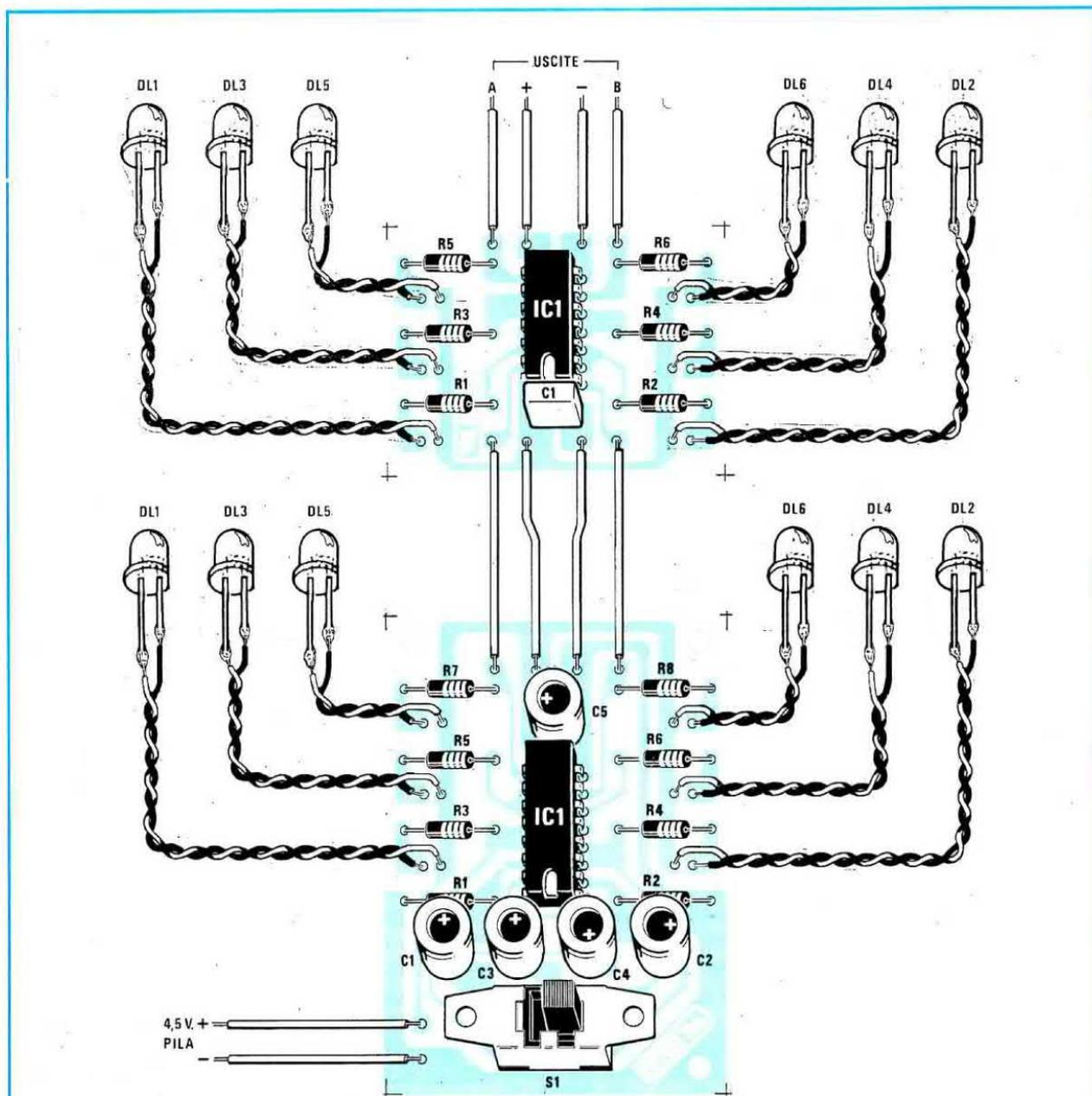
**Fig.10** In questo disegno vi facciamo vedere come si effettua un collegamento tra un circuito LX.865 ed un LX.866. Sull'uscita dell'LX.866 potremo collegare altri LX.866.
