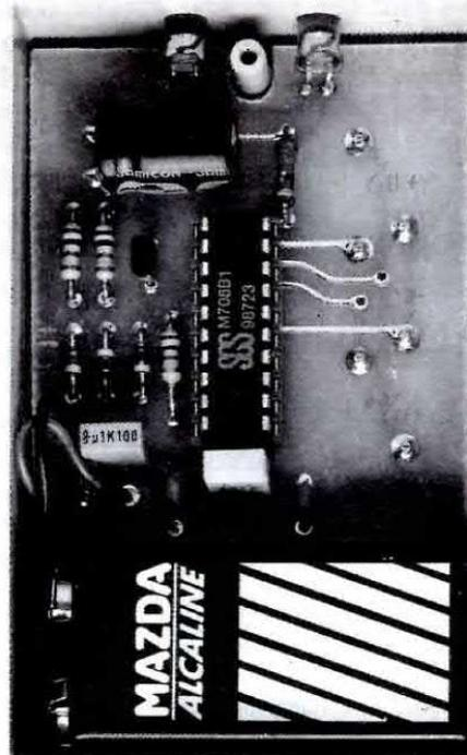
Fig.29 Nella foto il circuito del telecomando già inserito all'interno del contenitore plastico con la sua pila di alimentazione.
