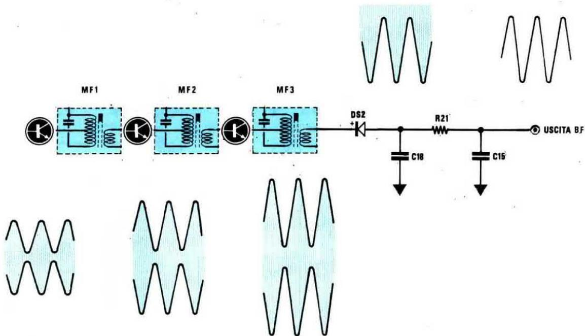
**Fig.13** Il segnale captato, convertito sulla frequenza di 455 KHz, verrà amplificato da due stadi di MF, poi applicato ad un diodo raddrizzatore al germanio DG2, che provvederà a lasciar passare le sole semionde "negative" dell'AF. Il condensatore C18, fucando a massa l'AF a 455 KHz, provvederà a separare da questa il solo segnale di BF.
