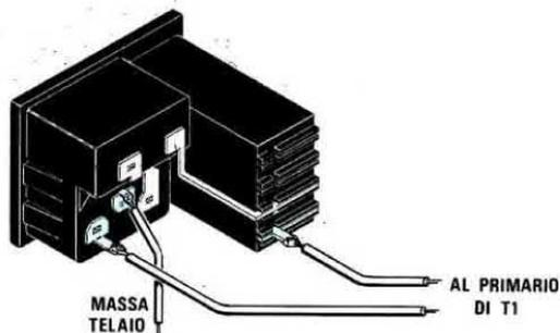
Fig.21 La presa rete che fisserete sul pannello posteriore del mobile, è completa dell'interruttore di accensione e di portafusibile. Non dimenticatevi di collegare con un filo il terminale visibile in disegno, alla "massa" metallica del mobile.
