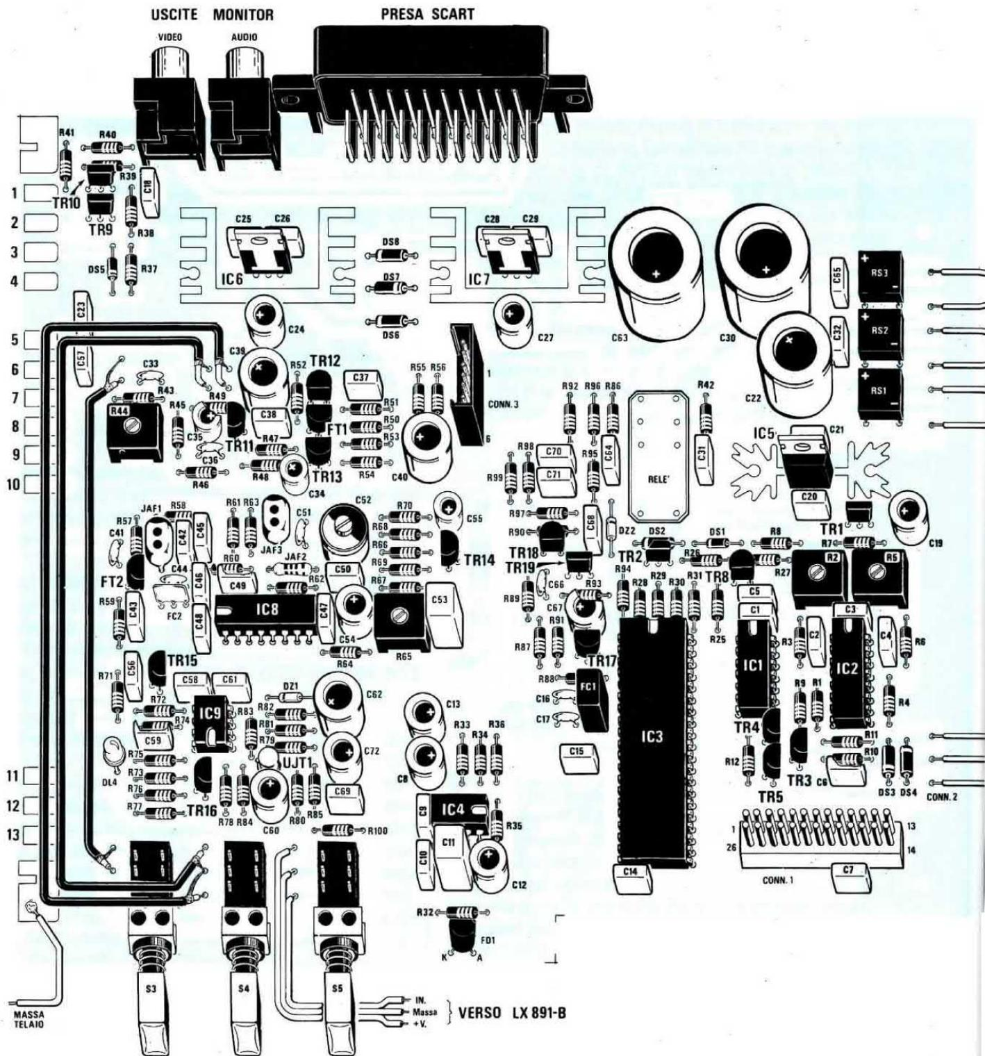
Fig.7 Schema pratico di montaggio del ricevitore per satelliti TV. In alto a sinistra sono visibili le due uscite Video-Audio per un monitor a colori e, vicino a queste, la presa SCART. Nota: Le alette di raffreddamento andranno fissate al circuito stampato con delle viti autofillettanti. Vi facciamo presente che è normale che la temperatura di queste alette raggiunga i 50/52 gradi. I diodi DS6-DS7-DS8 li dovrete tenere distanziati dallo stampato di circa 2 mm.
