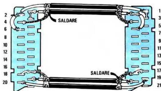
**Fig.19** Se non volete acquistare un cavo già cablato con i due connettori Scart, potrete facilmente autocostruirvelo, utilizzando due semplici cavetti coassiali, che collegherete ai due connettori come visibile in figura. Questo cavo è unidirezionale, cioè il connettore di destra andrà collegato al Televisore e il connettore di sinistra al Ricevitore.
