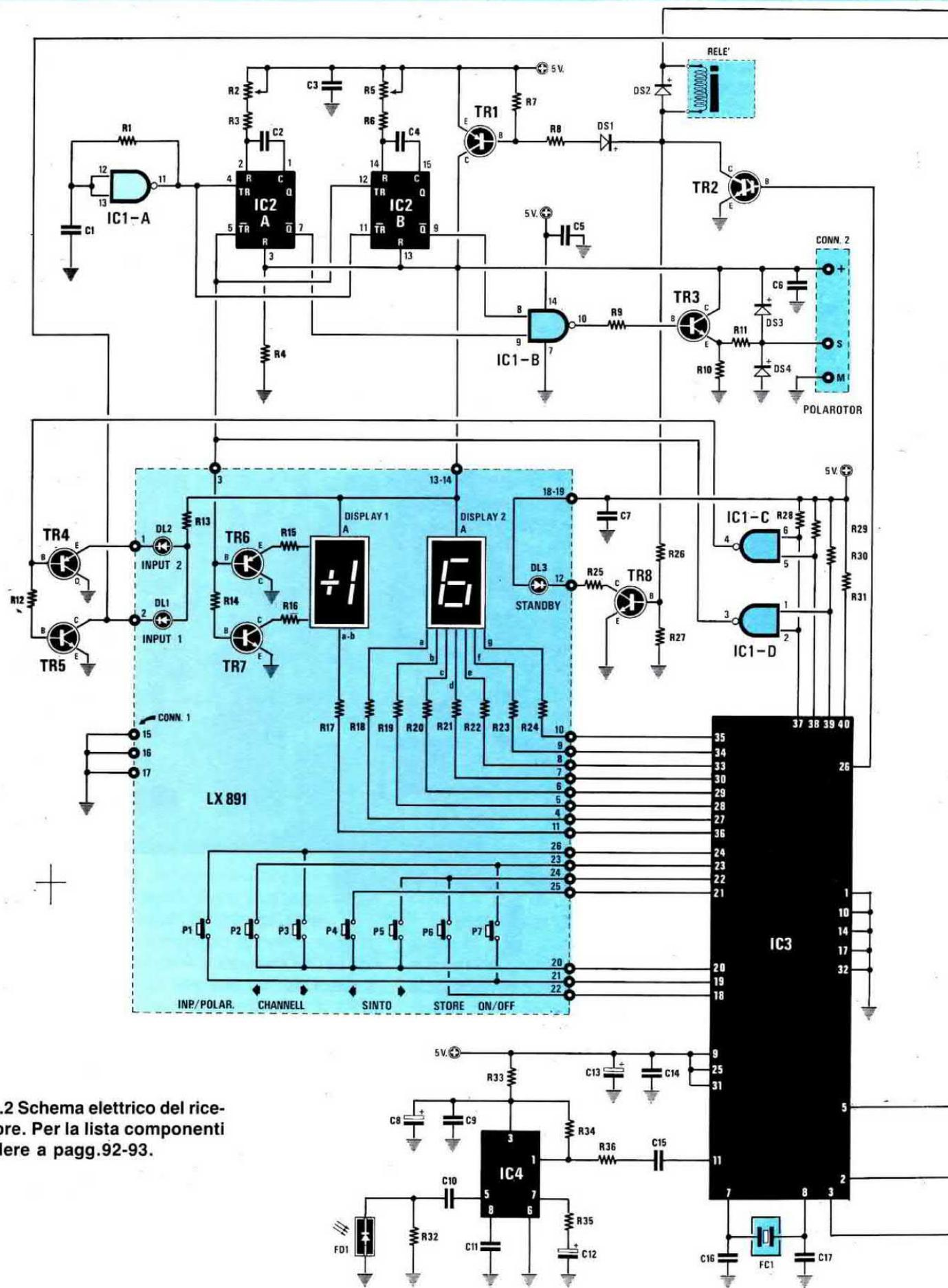
Fig.2 Schema elettrico del ricevitore. Per la lista componenti vedere a pagg.92-93.
