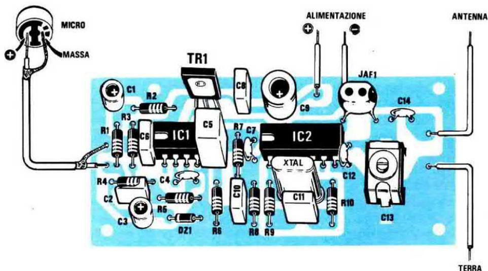
**Fig.15** Schema pratico di montaggio del microtrasmettitore ad Onde Corte. Si noti il cavetto schermato di collegamento con il microfono preamplificato (la calza dello schermo va collegata alla pista M) e la parte metallica di TR1 rivolta verso C5. Per raggiungere distanze elevate, è necessario collegare il filo "terra" ad una presa di acqua o ad un termosifone.
