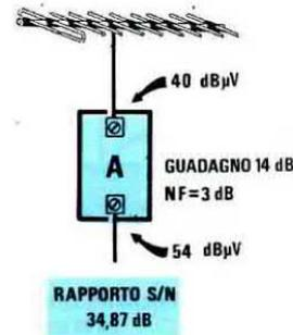
**Fig.226** Se avete un segnale debole da preamplificare, cercate di scegliere un preamplificatore in grado di fornirvi un "rapporto S/N" il più alto possibile, anche se in uscita non otterrete i dBmicrovolt richiesti.
