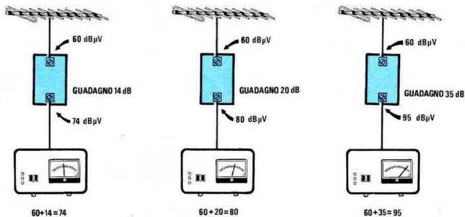
**Fig.222** Conoscendo i "dB" di guadagno del preamplificatore potrete calcolare, eseguendo una semplice addizione, quale segnale otterrete sulla sua uscita, applicando sull'ingresso X dBmicrovolt. Se l'antenna vi fornisce un segnale di 60 dBmicrovolt, utilizzando dei preamplificatori con guadagni di 14-20-35 dB, in uscita otterreste 74-80-95 dBmicrovolt.
