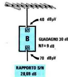
**Fig.227** Infatti, se sceglierete un preamplificatore ad alto guadagno, 30 dB e NF 9 dB (contro i 14 dB e NF 3 dB di fig.226), in uscita otterrete un forte segnale, ma con un rapporto S/N sfavorevole.
