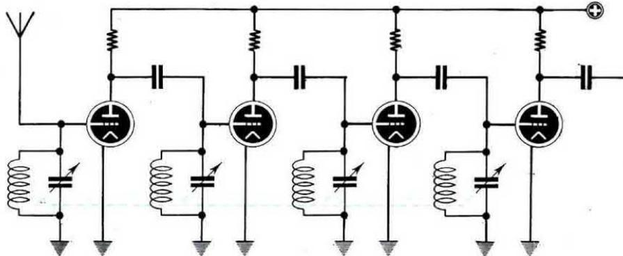
Fig.3 Nei primi ricevitori radio, anche applicando in ogni stadio amplificatore AF una bobina + condensatore variabile, la "selettività" oltre a non risultare ancora perfetta, rendeva questi ricevitori molti critici da tarare, quindi si cercò di trovare una diversa soluzione di questo inconveniente.
