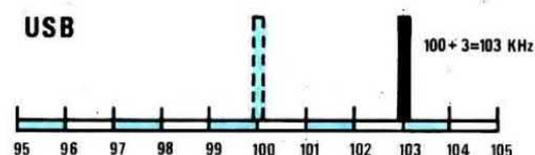
**Fig.2** Modulando una frequenza di 100 KHz in USB (Upper Side Band) con una nota di 1 KHz o di 3 KHz, la portante modulata si sposterà verso le frequenze più alte, cioè sui 101 KHz e 103 KHz.
