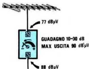
**Fig.233** Pertanto, se disponete di un preamplificatore che riporta come "Max segnale in uscita 90 dBµV" e l'antenna già vi fornisce un segnale di 77 dBmicrovolt, dovrete ruotare tale trimmer in modo da ottenere in uscita non più di 88 dBmicrovolt, per evitare che sul televisore appaiano delle venature nel colore.
