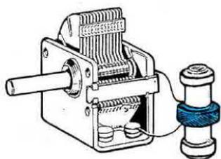
**Fig.8** Per ottenere un circuito di sintonia, occorre una bobina provvista di un certo numero di spire, con in parallelo un condensatore variabile in grado di modificare (per le Onde Medie) la sua capacità da un minimo di 24 pF ad un massimo di 250 pF.
