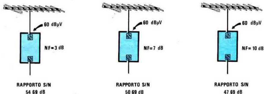
**Fig.224** La caratteristica più importante di un preamplificatore, specie se si debbono preamplificare segnali "deboli", è la Cifra di Rumore indicata con la sigla NF. Con questo dato potrete calcolare il Rapporto S/N, in base al quale potrete stabilire se il segnale amplificato è in grado di fornirvi una immagine Ottima-Passabile-Pessima (vedi tabelle n.11-12).
