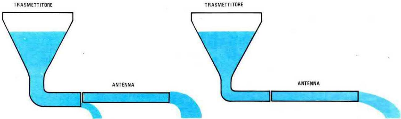
Fig.9 Vale a dire che se l'impedenza di uscita di un trasmettitore è minore (vedi fig.8) o maggiore rispetto a quella dell'antenna, si verificherebbero le stesse perdite che si producono in idraulica congiungendo insieme due tubi di diverso diametro.
