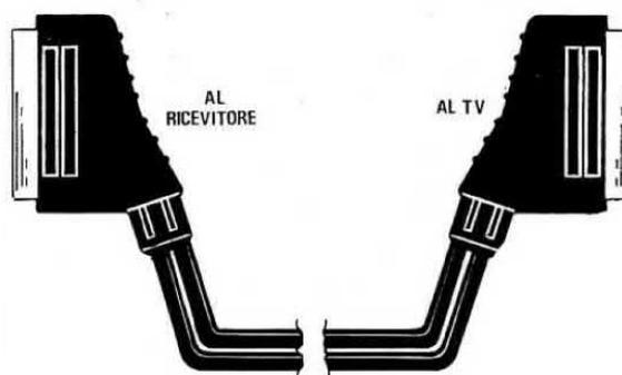
**Fig.20** Per non invertire i due connettori, indicate sul loro corpo quello che va al TV e quello che va al ricevitore. Se volete ottenere un cavo bidirezionale, dovrete utilizzare altri due cavetti schermati e collegarli come vedesi in fig.19 (cavetti di colore blu).
