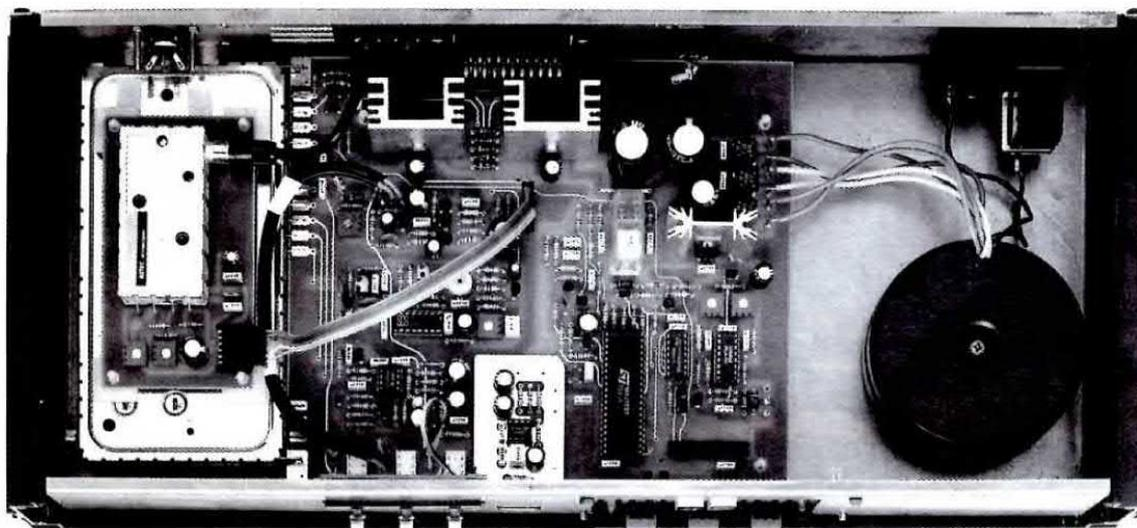
**Fig.16** In questa foto potete vedere come dovreste disporre all'interno del mobile il circuito stampato base LX.890 e il trasformatore toroidale di alimentazione. In questa foto risulta già fissato sul gruppo UHF, il modulatore Video/Audio presentato a pag.112.
