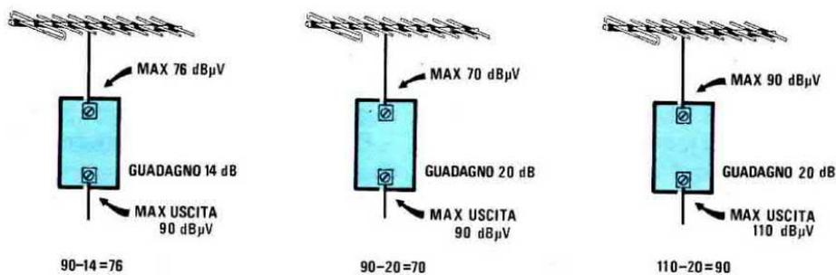
**Fig.223** Oltre al guadagno, su ogni preamplificatore dovrebbe essere riportato anche il "Max segnale in uscita". Questo dato serve per calcolare quale segnale massimo, in dBmicrovolt, potrete applicare sull'ingresso. Così, se avete un preamplificatore che Guadagna 20 dB, con un "Max uscita 90 dBμV", sul suo ingresso non potrete applicare più di  $90-20 = 70$  dBmicrovolt.
