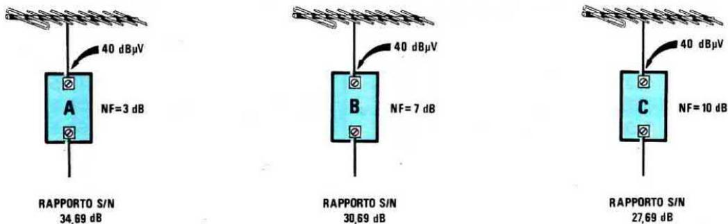
**Fig.225** In presenza di segnali molto deboli, dovrete sempre scegliere dei preamplificatori con NF molto basse. Ad esempio, con un segnale in antenna di 40 dBmicrovolt, solo il preamplificatore che ha una NF di 3 dB vi potrà fornire una "immagine buona", gli altri due con una NF di 7 dB e 10 dB vi daranno immagini scadenti, perchè il rapporto S/N è minore di 30 dB.
