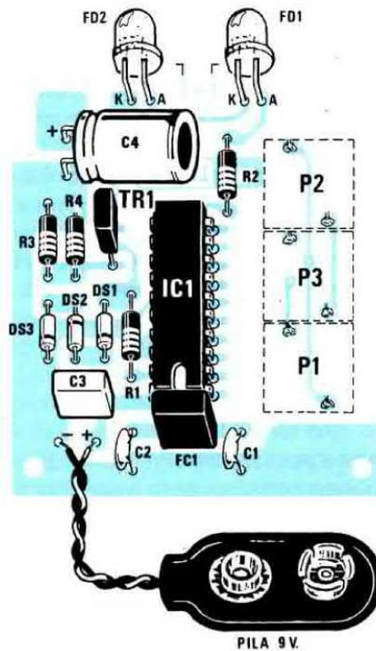
Fig. 27 In questa foto potrete facilmente intravedere i tre pulsanti di comando (P1 - P2 - P3), montati sul lato opposto di tale stampato. Ricordate di porre in posizione verticale il condensatore elettrolitico C4, se desiderate racchiuderlo entro il mobiletto plastico che forniamo assieme al kit (vedi figg.29-30).
