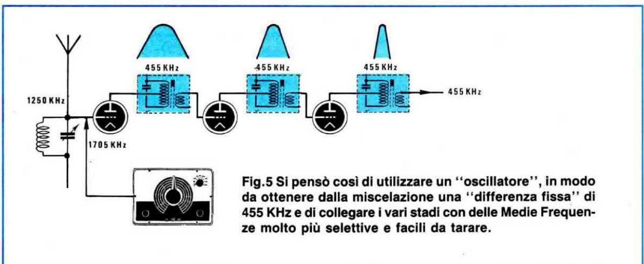
Fig.5 Si pensò così di utilizzare un "oscillatore", in modo da ottenere dalla miscelazione una "differenza fissa" di 455 KHz e di collegare i vari stadi con delle Medie Frequenze molto più selettive e facili da tarare.
