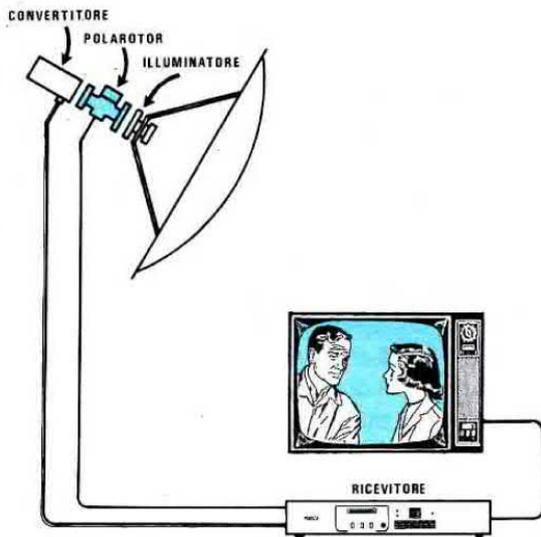
**Fig.5** Prima di fissare sul Convertitore LNC il Polarotor, che serve solo ed esclusivamente per passare dalla polarizzazione orizzontale a quella verticale o viceversa, sarebbe consigliabile centrare la parabola sul satellite, utilizzando il solo Convertitore. Captata una emittente, si fissa la parabola in modo stabile, dopodichè si potrà inserire il Polarotor e tarare i due trimmer R2 - R5 per il massimo segnale, vale a dire fino ad ottenere una immagine perfetta senza tracce di rumore.
