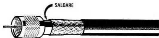
Fig.23 Una volta infilato il cavo tanto da far fuoriuscire il filo centrale che userete come spinotto, dovrete saldare la calza metallica sulla massa del connettore come visibile in disegno.
