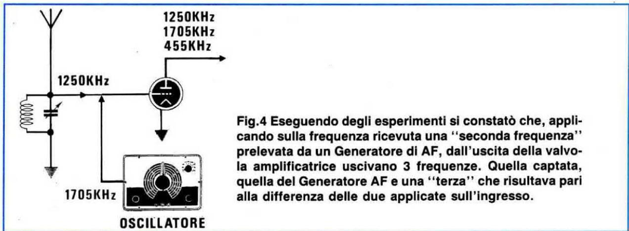
Fig.4 Eseguendo degli esperimenti si constatò che, applicando sulla frequenza ricevuta una "seconda frequenza" prelevata da un Generatore di AF, dall'uscita della valvola amplificatrice uscivano 3 frequenze. Quella captata, quella del Generatore AF e una "terza" che risultava pari alla differenza delle due applicate sull'ingresso.
