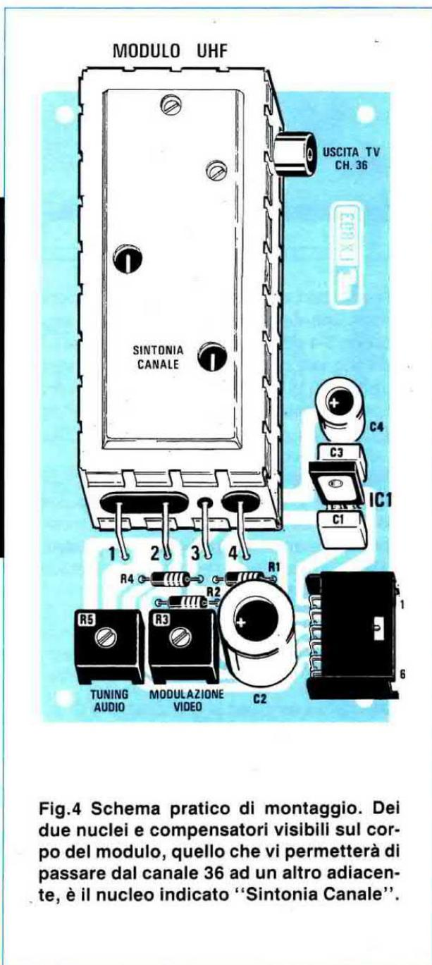
**Fig.4** Schema pratico di montaggio. Dei due nuclei e compensatori visibili sul corpo del modulo, quello che vi permetterà di passare dal canale 36 ad un altro adiacente, è il nucleo indicato "Sintonia Canale".
