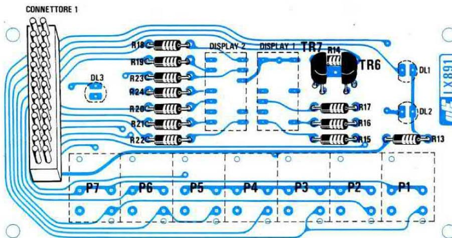
Fig.10 Schema pratico di montaggio del circuito stampato LX.891 visto da entrambi i lati. Per collegare questo stadio al circuito base del ricevitore, troverete nel kit una piattina già cablata con i due connettori.
