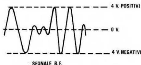
**Fig.1** Analizzando un segnale di bassa frequenza con un tester che disponga di uno 0 centrale o ancor meglio con un oscilloscopio, noterete tante semionde positive e le corrispondenti semionde negative. L'ampiezza massima (volt picco-picco) dipende dalla potenza del segnale analizzato.
