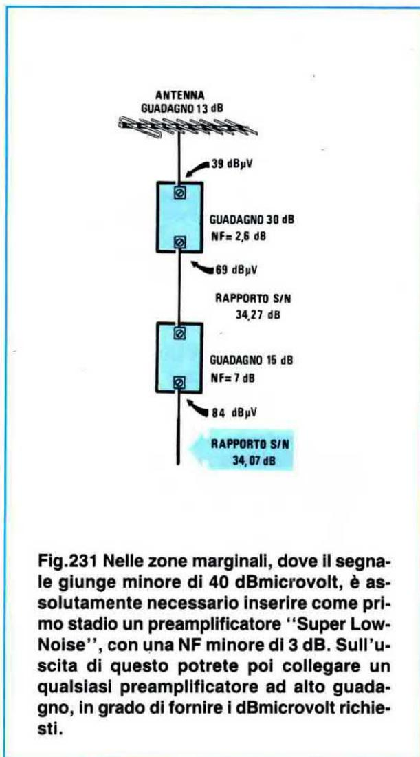
**Fig.231** Nelle zone marginali, dove il segnale giunge minore di 40 dBmicrovolt, è assolutamente necessario inserire come primo stadio un preamplificatore "Super Low Noise", con una NF minore di 3 dB. Sull'uscita di questo potrete poi collegare un qualsiasi preamplificatore ad alto guadagno, in grado di fornire i dBmicrovolt richiesti.
