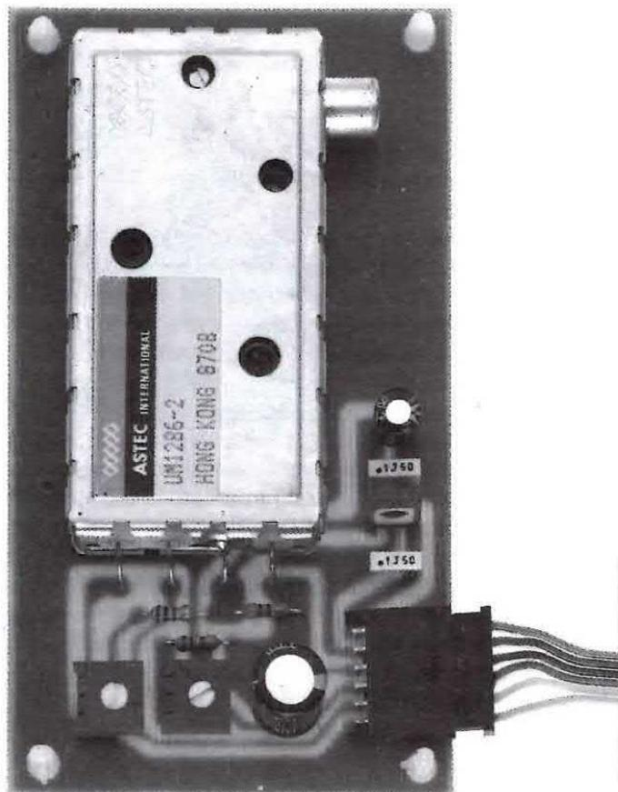
**Chi ha realizzato il ricevitore per satelliti TV e malauguratamente non dispone nel proprio televisore di una presa ingresso Scart, dovrà inserire all'interno del ricevitore questo "modulatore Video/Audio", per ottenere un segnale UHF sintonizzato sul canale 36. Tale modulatore può servire anche per ricavare da dei normali segnali Video/Audio di bassa frequenza, un segnale di AF sulla banda UHF, che potrete facilmente sintonizzare sui canali TV 34-35-36-37-38.**
