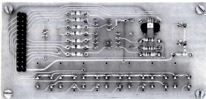
Fig. 13 Dal lato opposto potete vedere i due transistor TR7-TR6 e a sinistra il connettore di collegamento.
