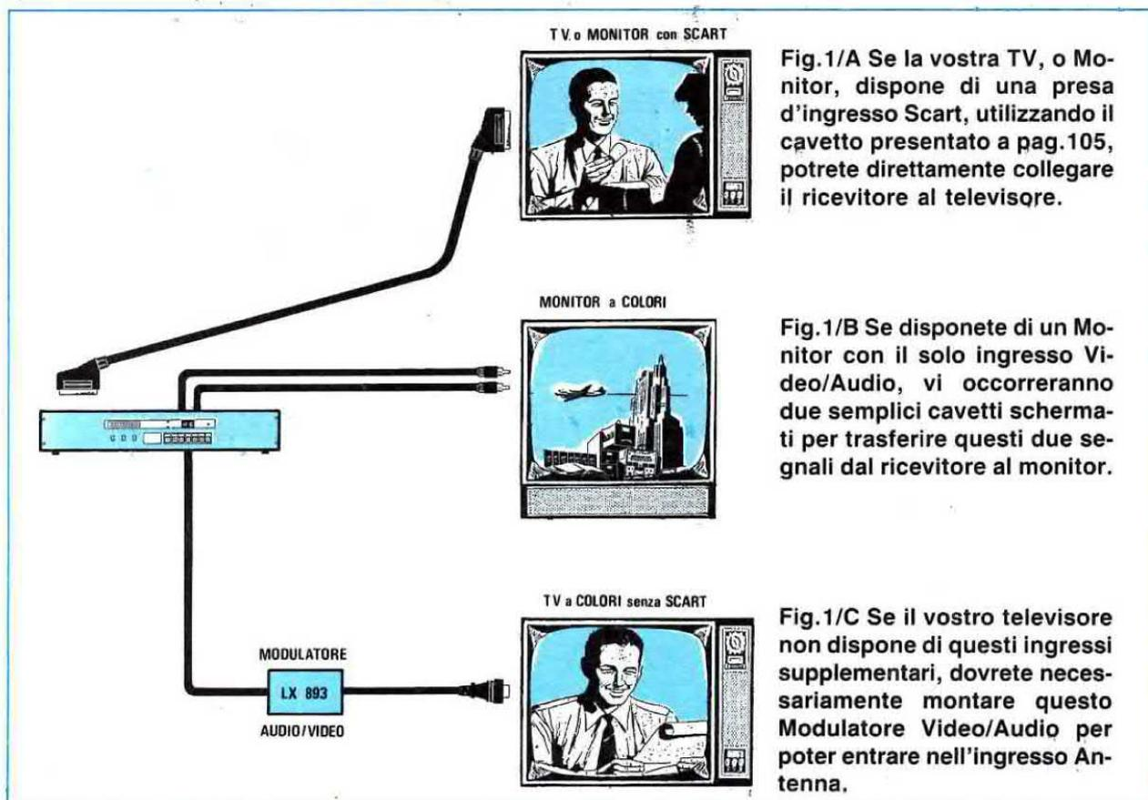
Fig.1/A Se la vostra TV, o Monitor, dispone di una presa d'ingresso Scart, utilizzando il cavetto presentato a pag.105, potrete direttamente collegare il ricevitore al televisore.
