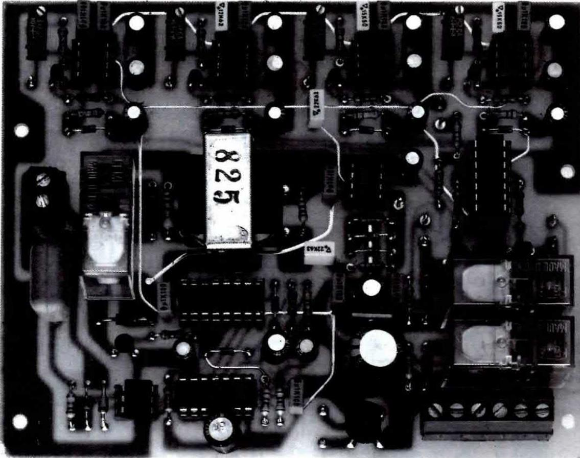
**Fig.6** Come si presenterà a montaggio ultimato la scheda dello stadio ricevente di questo telecomando telefonico. Si notino le morsettiere per l'ingresso della linea telefonica e per l'uscita dei relè.
