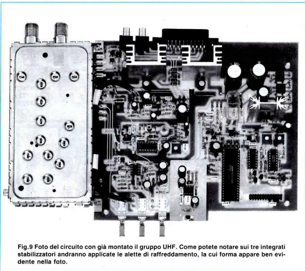
Fig.9 Foto del circuito con già montato il gruppo UHF. Come potete notare sui tre integrati stabilizzatori andranno applicate le alette di raffreddamento, la cui forma appare ben evidente nella foto.
