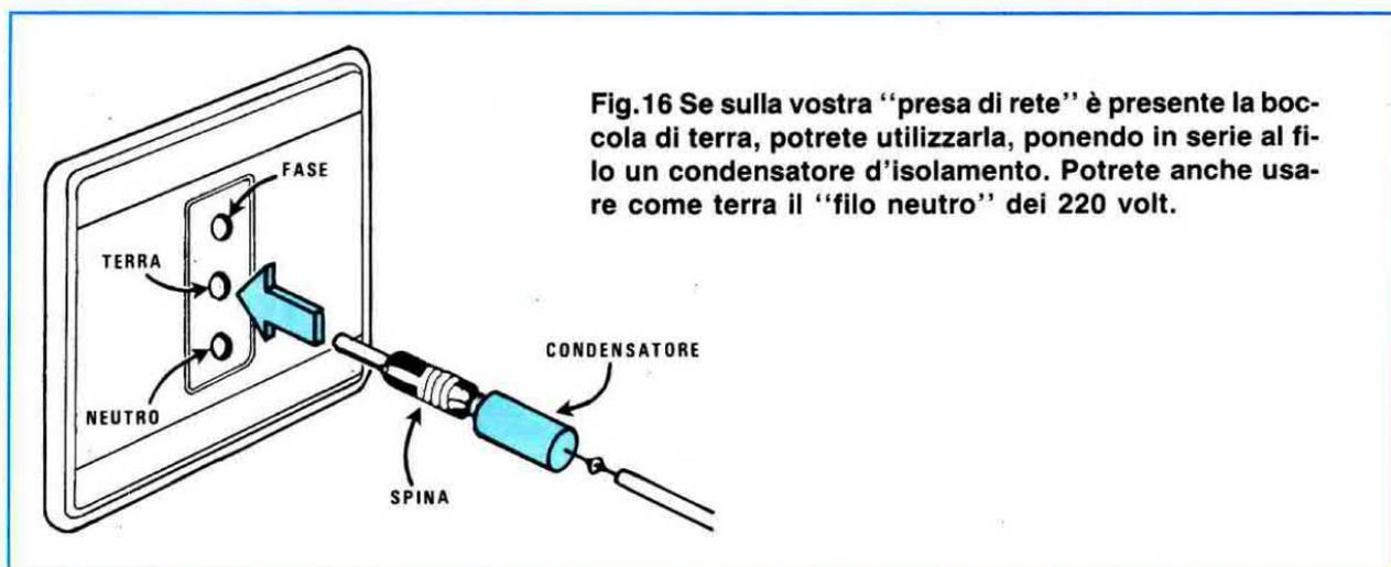
**Fig.16** Se sulla vostra "presa di rete" è presente la boccia di terra, potrete utilizzarla, ponendo in serie al filo un condensatore d'isolamento. Potrete anche usare come terra il "filo neutro" dei 220 volt.
