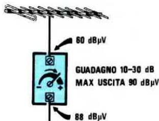
**Fig.232** Se il segnale in antenna risulterà elevato, dovrete verificare che il segnale che otterrete sulla sua uscita non superi il "livello Max" consentito dal preamplificatore. Come noterete, su ogni preamplificatore è sempre presente un trimmer, che vi permetterà di regolare l'amplificazione da un minimo ad un massimo.
