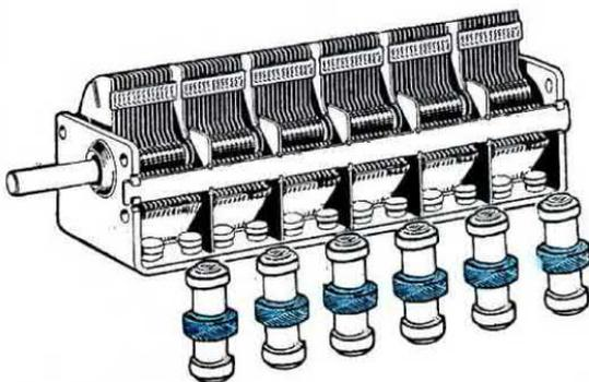
**Fig.2** Aumentando il numero delle emittenti, si dovette aumentare il numero dei circuiti di sintonia, in modo da restringere la banda passante e, di conseguenza, aumentare le sezioni del condensatore variabile.
