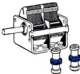
Fig.10 In un ricevitore supereterodina occorre sempre un "doppio" condensatore variabile. Una sezione verrà utilizzata per sintonizzarsi sulla emittente da captare e l'altra per modificare la frequenza sullo stadio oscillatore locale.
