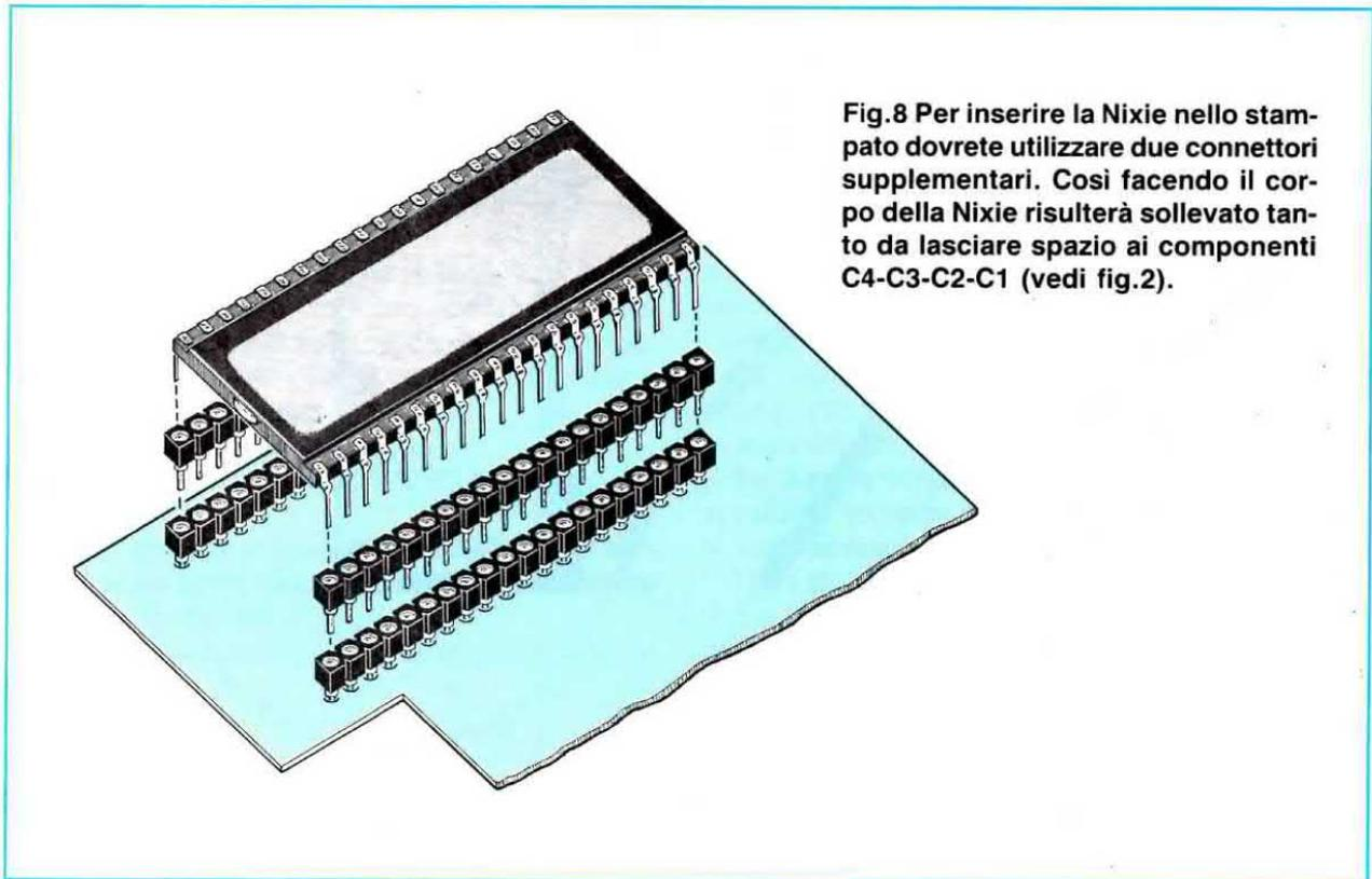
Fig.8 Per inserire la Nixie nello stampato dovrete utilizzare due connettori supplementari. Così facendo il corpo della Nixie risulterà sollevato tanto da lasciare spazio ai componenti C4-C3-C2-C1 (vedi fig.2).
