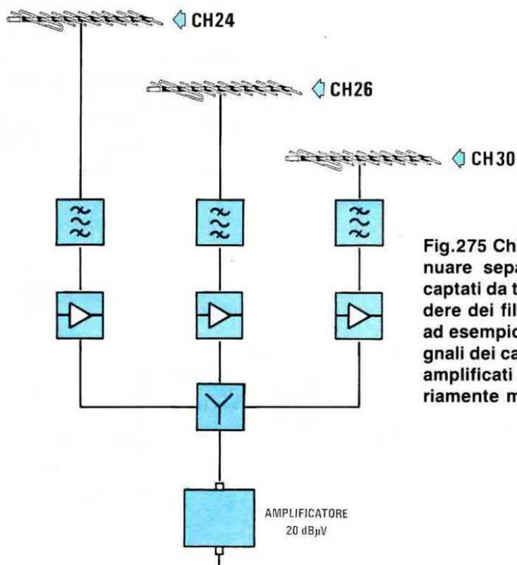
Fig.275 Chi volesse preamplificare o attenuare separatamente tre diversi canali, captati da tre singole antenne, potrà prendere dei filtri "passa-canale" sintonizzati ad esempio su Ch.24 - Ch.26 - Ch.30. I segnali dei canali prescelti dopo essere stati amplificati o attenuati, andranno necessariamente miscelati.
