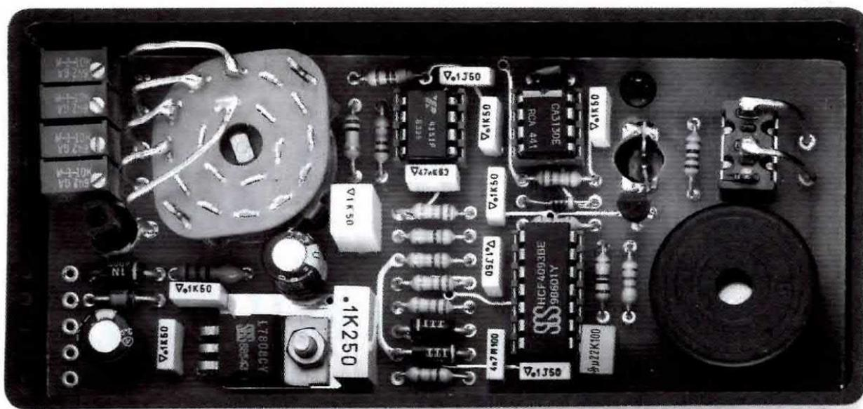
**Fig.5 Il circuito verrà fissato entro il mobiletto plastico che risulta già incluso nel kit. Sul coperchio del mobile dovreste solo praticare tre fori, uno per il commutatore, uno per il deviatore ed uno per il diodo led.**
