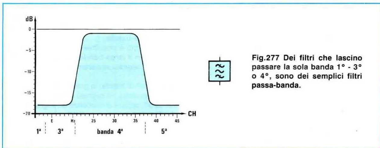
Fig.277 Dei filtri che lascino passare la sola banda 1° - 3° o 4°, sono dei semplici filtri passa-banda.
