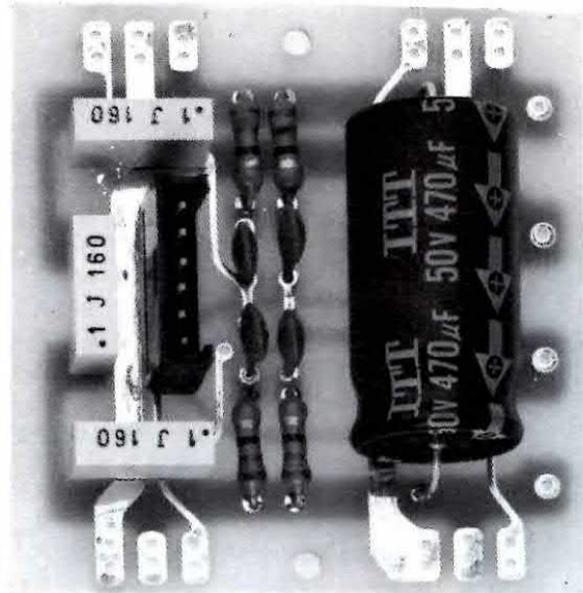
Fig.9 Foto dello stampato LX.911 da montare sulle alette di raffreddamento del mobile (vedi fig.14).
