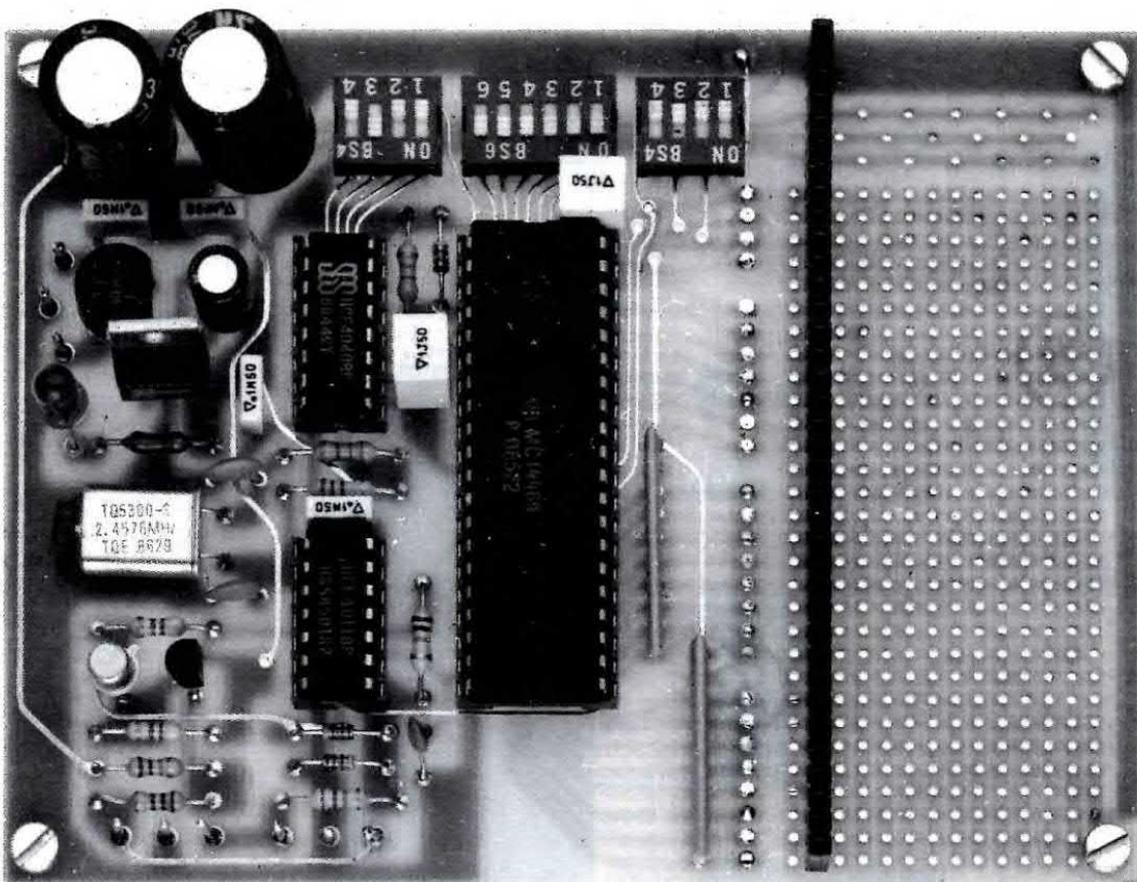
Fig.3 Foto della scheda Seriale/Parallela come si presenterà a montaggio ultimato. La superficie mille fori presente sul lato destro di tale scheda, la potremo utilizzare per montare tutti i circuiti che vorremo pilotare, cioè transistor, integrati, display, ecc. (vedi da fig.11 a fig.21).
