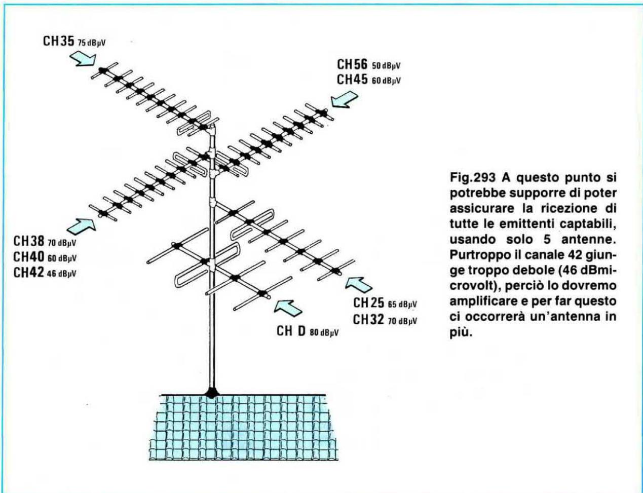
Fig.293 A questo punto si potrebbe supporre di poter assicurare la ricezione di tutte le emittenti captabili, usando solo 5 antenne. Purtroppo il canale 42 giunge troppo debole (46 dBmicrovolt), perciò lo dovremo amplificare e per far questo ci occorrerà un'antenna in più.
