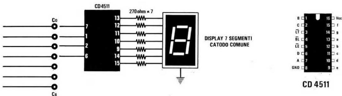
Fig.16 Collegando alle uscite gli ingressi 7-1-2-6 di un integrato CD.4511 (alimentato a 5 volt), potremo pilotare un qualsiasi display a Catodo Comune. È ovvio che dalle uscite da C0 a C3 dovremo far uscire un codice binario BCD.
