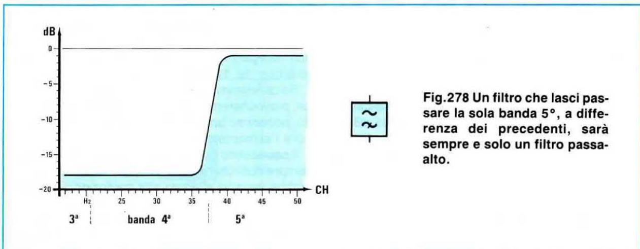
Fig.278 Un filtro che lasci passare la sola banda 5°, a differenza dei precedenti, sarà sempre e solo un filtro passa-alto.
