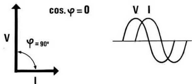
Fig.7 Riducendosi i gradi dello sfasamento, il cos-fi da 0,6 passerà a 0,7, poi a 0,8, a 0,9, per arrivare, a linea rifasata, ad un cos-fi = 1. Le norme vigenti impongono che il cos-fi non risulti mai "minore di 0,9", cioè che non abbia un angolo di sfasamento maggiore di 25,84 gradi.
