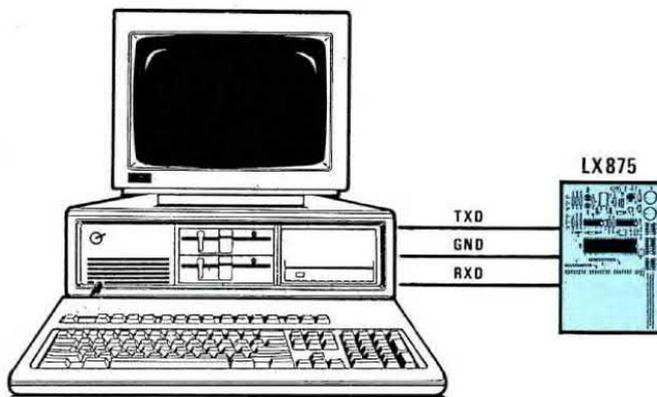
Fig.1 Per collegare questa interfaccia Seriale/Parallela al computer servono solo 3 fili. Per i collegamenti al connettore vedere fig.9.
