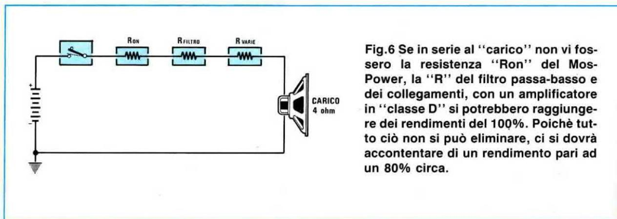
Fig.6 Se in serie al "carico" non vi fossero la resistenza "Ron" del Mos-Power, la "R" del filtro passa-basso e dei collegamenti, con un amplificatore in "classe D" si potrebbero raggiungere dei rendimenti del 100%. Poichè tutto ciò non si può eliminare, ci si dovrà accontentare di un rendimento pari ad un 80% circa.
