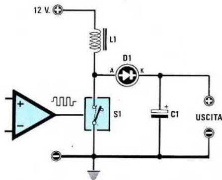
**Fig.2** Chiudendo l'interruttore S1, nella bobina L1 si immagazzinerà una potenza che risulterà proporzionale al valore della tensione e della induttanza. Quando l'interruttore si aprirà, per il noto fenomeno della autoinduzione, questa bobina genererà una "extratensione" inversa che, passando attraverso il diodo D1, potrà caricare il condensatore elettrolitico C1.
