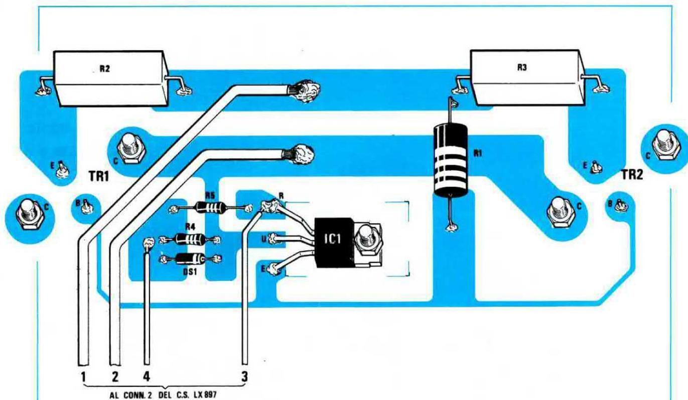
**Fig.7 Schema pratico di montaggio dello stampato LX.898. I terminali dei fili siglati 1-2 e 4-3 provenienti dallo stampato LX.897 (vedi fig.6), andranno saldati direttamente sulle piste in rame dello stampato. Le resistenze R1-R2 si dovranno tenere leggermente distanziate dallo stampato.**
