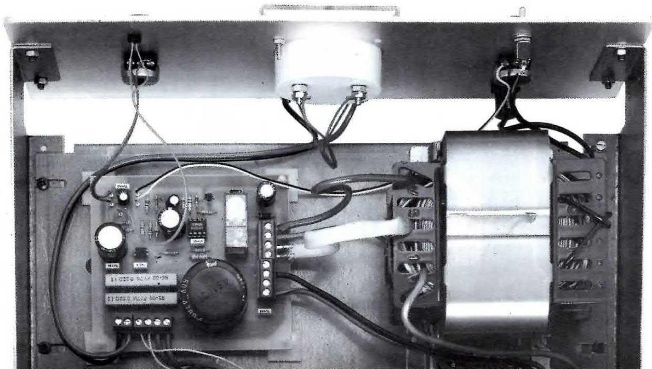
Fig.9 Come vedesi in questa foto, il grosso trasformatore d'alimentazione verrà fissato sul piano base del mobile. Il pannello di questo mobile completo di serigrafia, verrà fornito già forato per ricevere i due potenziometri, il fusibile, le boccole d'uscita e uno strumento da 30 volt fondo scala.
