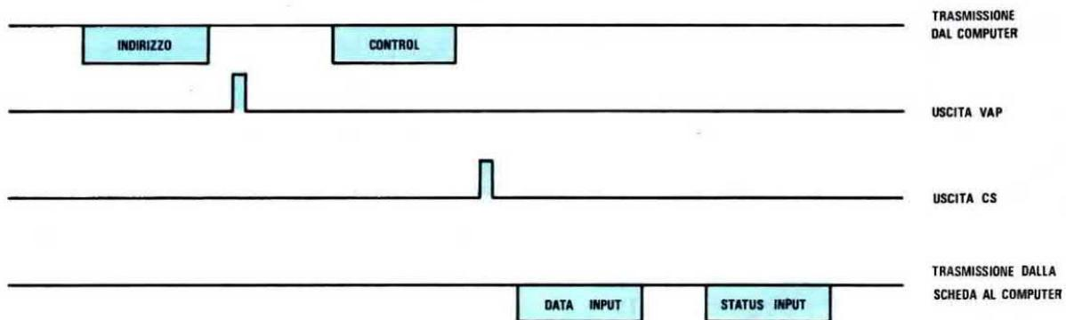
**Fig.7** Diagramma temporale di Ricezione-Trasmissione (MODO 2). Funziona come il MODO 1, però la scheda, dopo la ricezione dell'indirizzo e del controllo, ritrasmette verso il computer i due ingressi a 8 bit denominati DATA INPUT e STATUS INPUT. In questo modo la parola di controllo può essere usata per condizionare la risposta della scheda.
