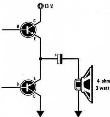
**Fig.2** Alimentando con una tensione di 13 volt un qualsiasi finale di BF provvisto di un altoparlante da 4 ohm, la massima potenza che potrete ottenere non supererà mai i 3 watt "efficaci". Per raddoppiare la potenza si potrebbero usare degli altoparlanti da 2 ohm.
