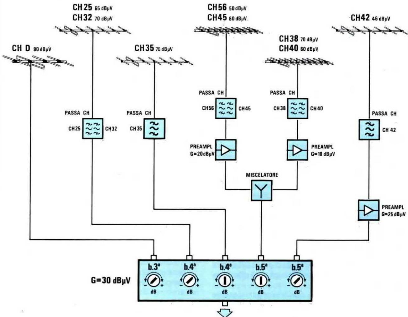
Fig.294 Una volta in possesso di tutti i dati richiesti, potremo progettare a casa nostra l'impianto completo, calcolando teoricamente se sull'uscita dell'amplificatore tutti i segnali escono con il livello minimo richiesto.
