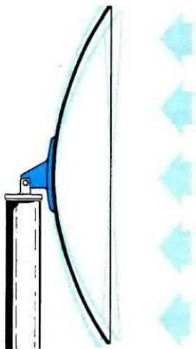
**Fig.14** Un supporto, che abbracci al centro una ristretta superficie della parabola, in presenza di forti venti non impedirà che questa oscilli e, conseguentemente, la ricezione di una qualsiasi emittente non risulterà regolare.
