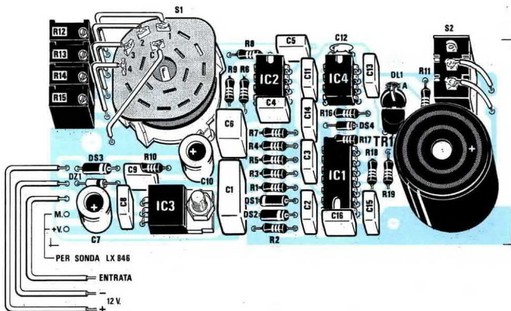
**Fig.4 Schema pratico di montaggio. I due fili +/- 12 volt andranno collegati alla batteria e quello indicato "Entrata" allo spinterogeno. Per le auto Diesel dovreste aggiungere una sonda siglata LX.846 che abbiamo presentato nella rivista n.121/122.**
