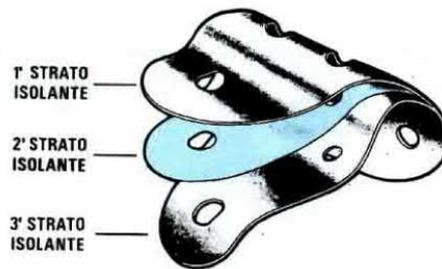
**Fig.3** Per trasferire velocemente il calore generato dai due finali verso l'aletta di raffreddamento, si consiglia di utilizzare per questo progetto le speciali miche Sil-Pad inserite nel kit. In caso contrario dovrete spargere sotto il corpo del transistor del grasso al silicone.
