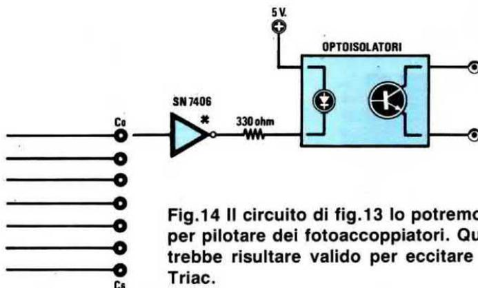
Fig.14 Il circuito di fig.13 lo potremo utilizzare anche per pilotare dei fotoaccoppiatori. Questo circuito potrebbe risultare valido per eccitare dei diodi SCR o Triac.
