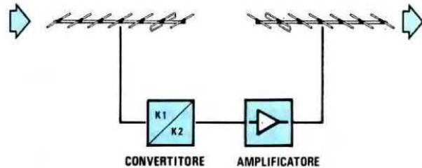
**Fig.291** Se la potenza del nostro “minitrasmittitore” non ci soddisfa, potremo inserire dopo il convertitore un “finale di potenza” a larga banda del tipo utilizzato negli impianti centralizzati.
