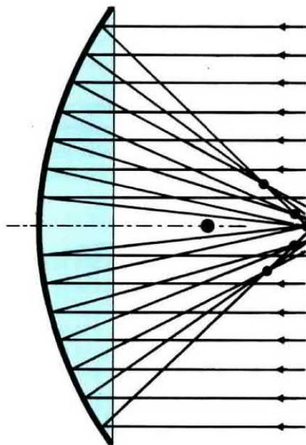
**Fig.9** Se questo profilo non dispone di una ben calcolata curvatura (vedi fig.10), il rendimento potrà scendere anche sotto ad un 50%, perchè parte del segnale captato verrà deviato fuori del punto focale.
