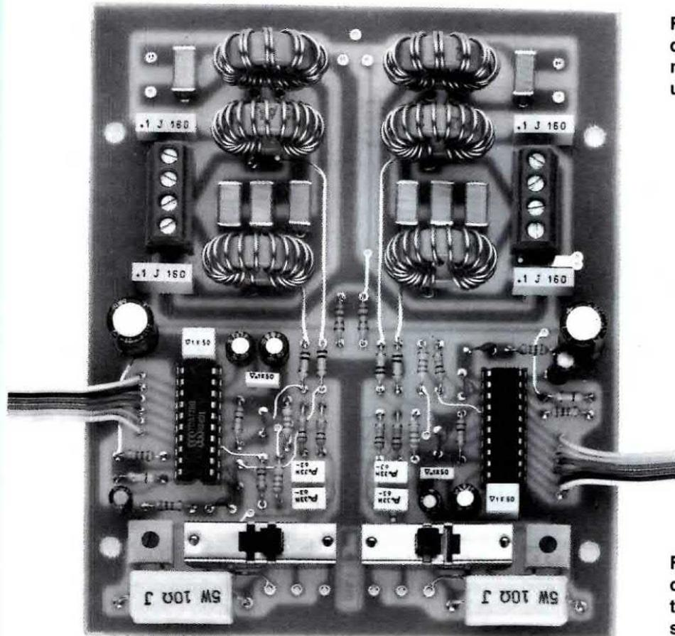
Fig.11 Foto dello stampato LX.910 come si presenterà a montaggio ultimato. Si notino le 6 bobine avvolte su nucleo toroidale.
