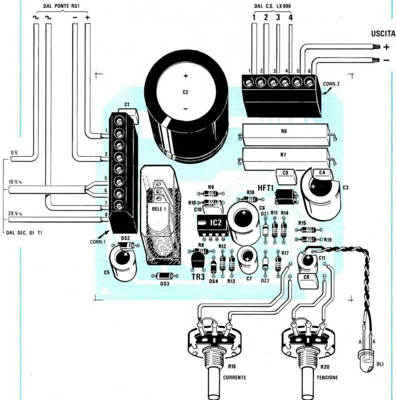
Fig.6 Schema pratico di montaggio dello stadio base LX.897. La morsetteria posta sul lato sinistro dello stampato servirà per entrare con i 16-18 volt del secondario del trasformatore T1, per portare questa tensione sul ponte raddrizzatore RS1 e per rientrare con la tensione già raddrizzata. La morsetteria posta in alto a destra, per collegarsi con lo stampato LX.898 (vedi fig.7) e per portare la tensione stabilizzata sui morsetti d'uscita.
