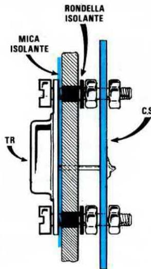
**Fig.4** Collocata la mica tra transistor ed aletta, non dimenticatevi di porre sotto al dado di fissaggio la rondella isolante per poter così isolare il corpo del transistor. Come vedesi nel disegno, il circuito stampato LX.898 verrà tenuto distanziato dall'aletta di raffreddamento dai due dadi posti sotto il transistor.
