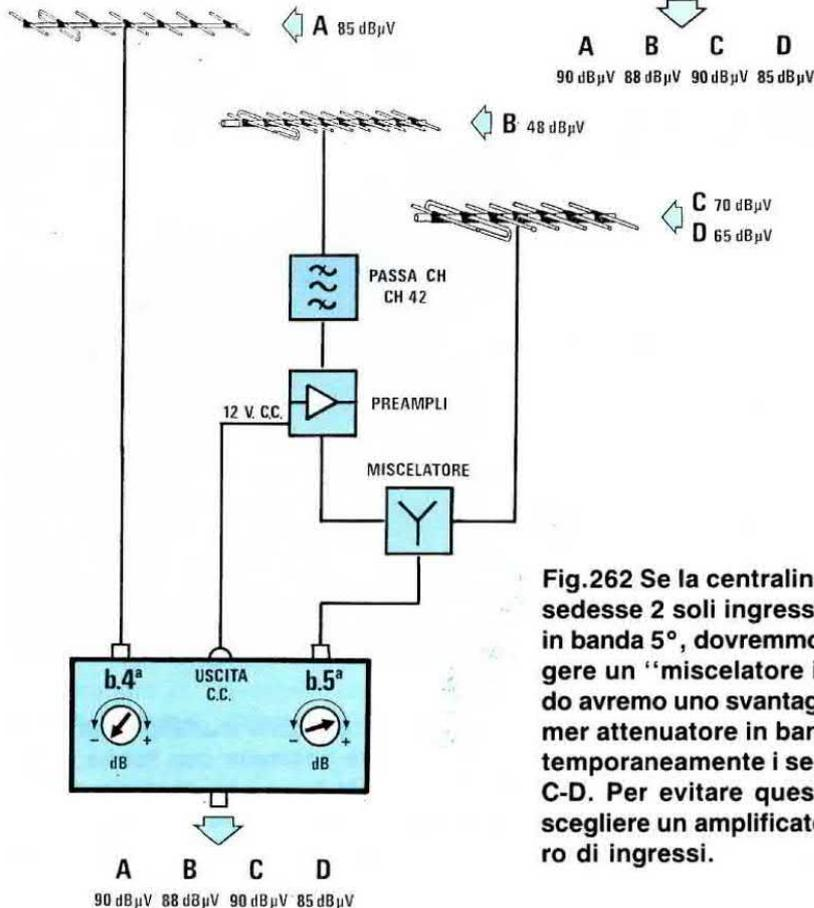
Fig.262 Se la centralina in nostro possesso possedesse 2 soli ingressi, uno in banda 4° ed uno in banda 5°, dovremmo necessariamente aggiungere un "miscelatore in banda 5°". Così facendo avremo uno svantaggio, cioè, agendo sul trimmer attenuatore in banda 5°, atteneremo contemporaneamente i segnali delle tre emittenti B-C-D. Per evitare questo inconveniente, meglio scegliere un amplificatore con un maggior numero di ingressi.
