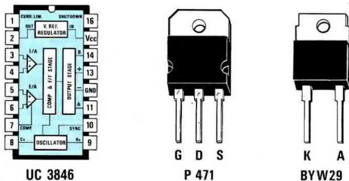
Fig.5 Connessioni interne dell'integrato UC.3846 e disposizione dei terminali dei Mos-Power P.471 e dei diodi fast BYW.29.
