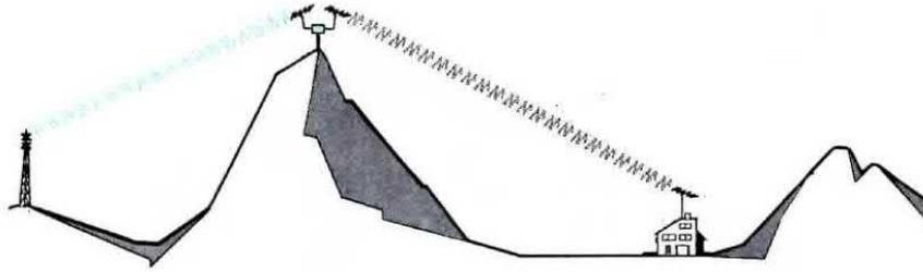
**Fig.290** Un convertitore di canale può servire anche per realizzare dei semplici “miniripetitori”, per far giungere la TV in molte zone d’ombra. Il segnale captato da un’antenna ricevente, dopo essere stato convertito lo applicheremo ad un’antenna non molto direttiva, che direzioneremo verso la zona da servire.
