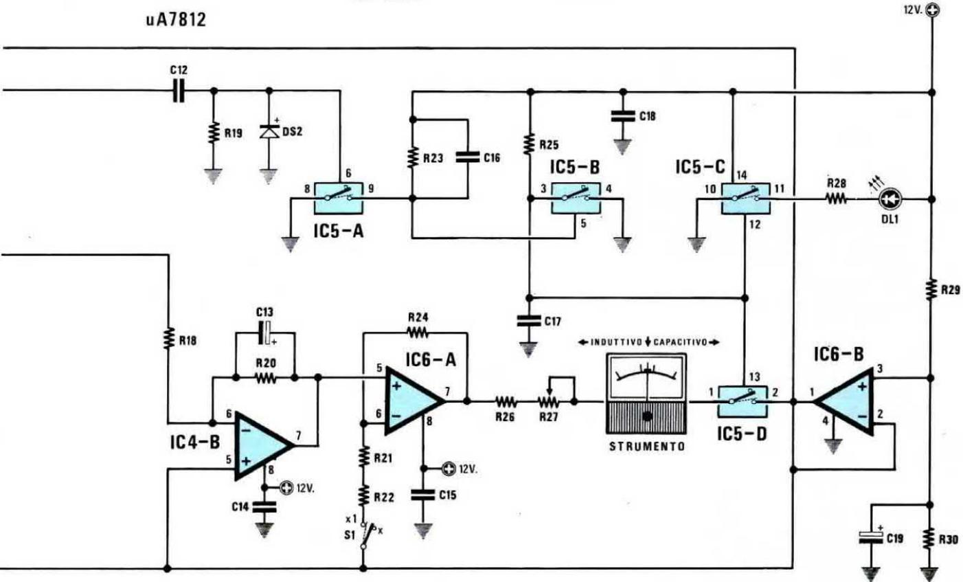
Fig.11 Schema elettrico del Fasometro e connessioni degli integrati visti da sopra.
