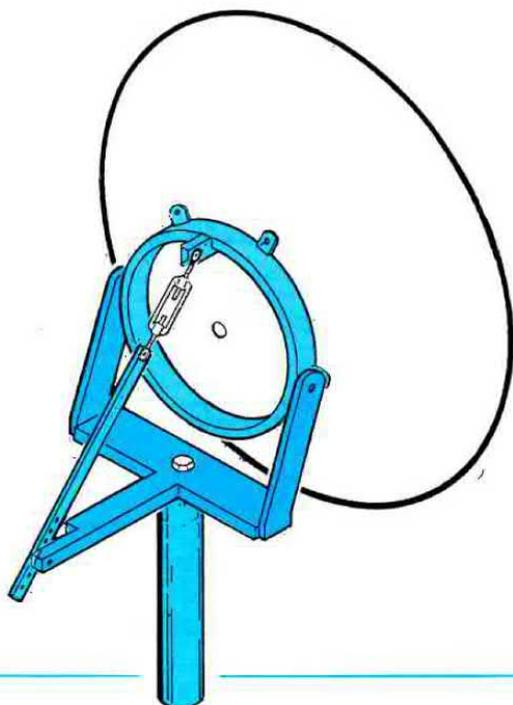
**Fig.17** Una volta fissato questo supporto sulla parabola, per lo spostamento metrico verticale sfrutterete il tendifilo fissato sull'asta, mentre per uno spostamento più consistente, utilizzerete i fori posti all'estremità della stessa asta. Per lo spostamento in orizzontale farete perno sul bullone di fissaggio presente sul palo di sostegno.
