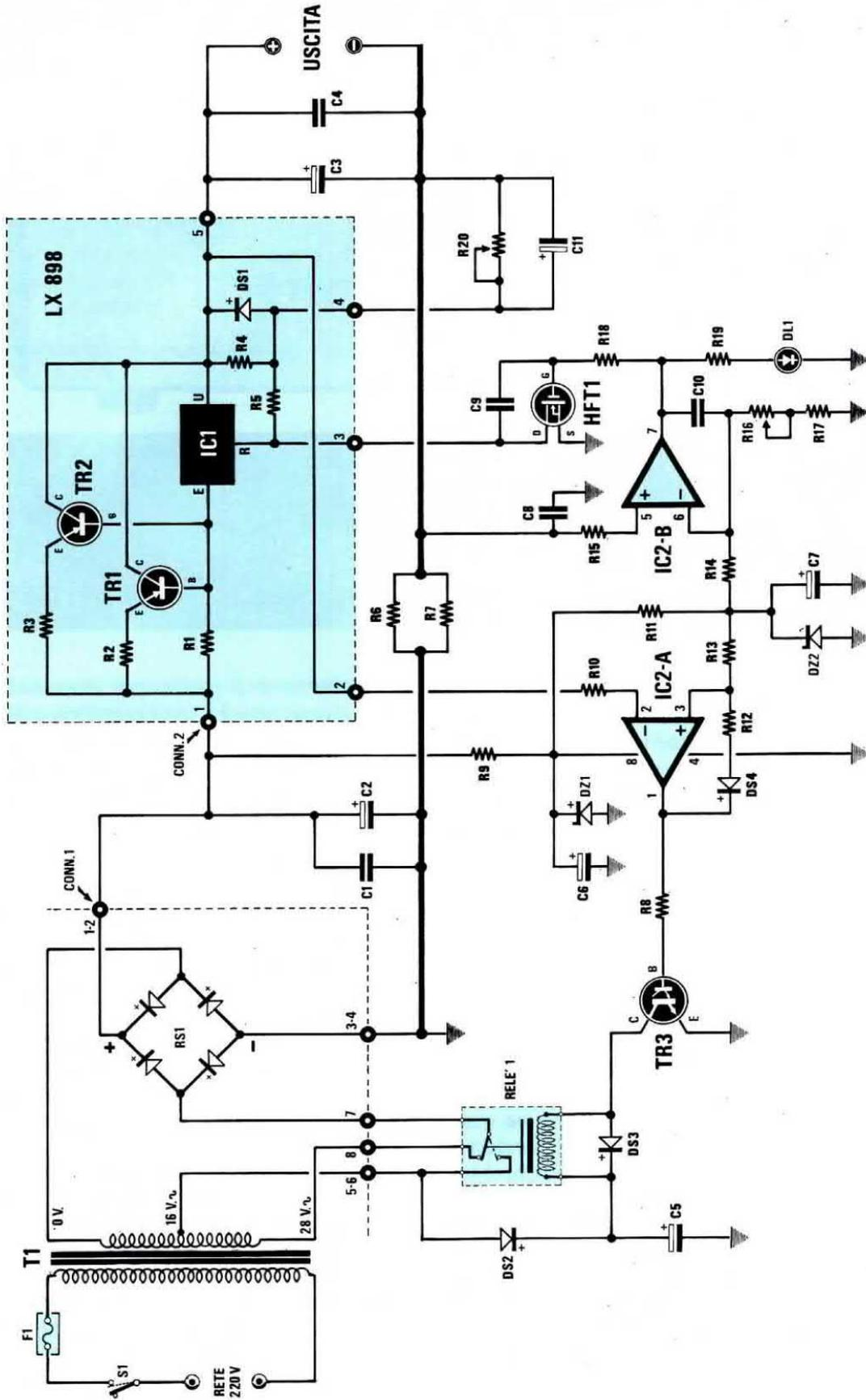
Fig.1 Schema elettrico dell'alimentatore da 10 amper massimi.
