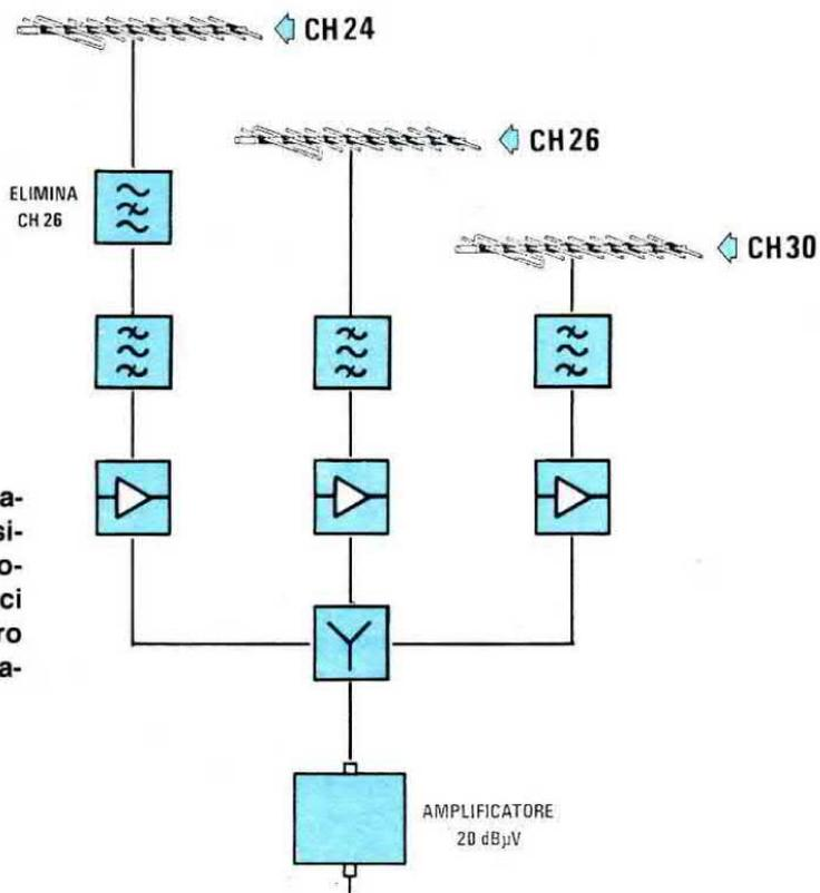
Fig.276 Se sull'uscita del filtro del canale 24 risultasse presente un residuo del canale 26 che giunge in zona con un segnale troppo forte, ci converrà inserire prima del filtro passa-canale 24 un filtro "elimina canale 26".
