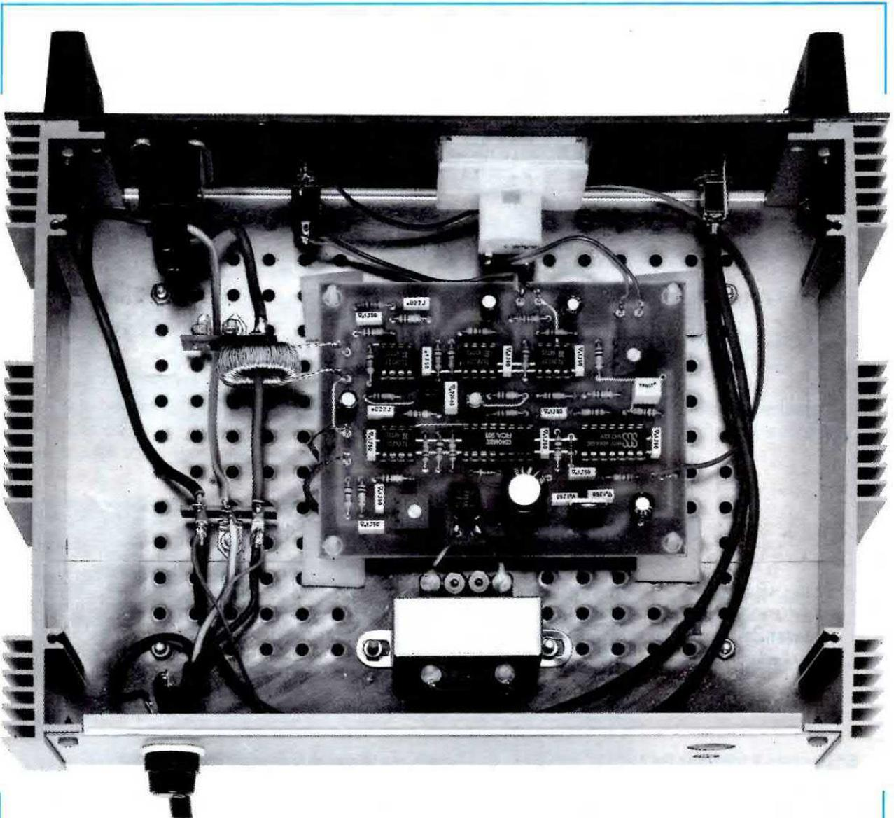
**Fig. 14** Ecco come dovremo fissare all'interno del mobile il trasformatore di alimentazione, il circuito stampato e il nucleo toroidale L1. Poichè la tensione dei 220 volt presente sulla presa "uscita carico" viene prelevata direttamente dal cordone di alimentazione che alimenta T1, non potremo applicare dei carichi che assorbano più di 10 amper.
