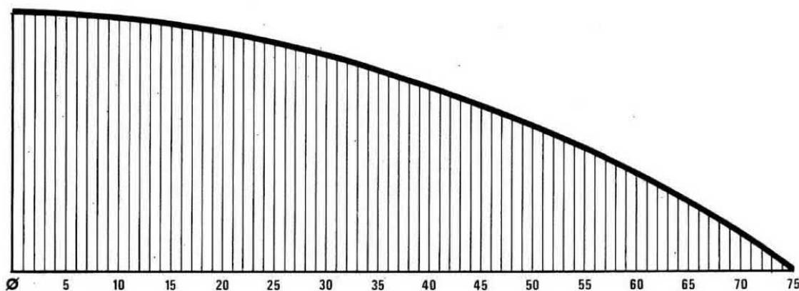
**Fig.11** Congiungendo tutte le estremità di queste linee verticali "X", ricaverete l'esatto profilo di metà parabola. Conoscere l'altezza "X" punto per punto di una parabola, vi potrebbe risultare molto utile per verificare se una parabola di tipo commerciale risulta sagomata in modo regolare.
