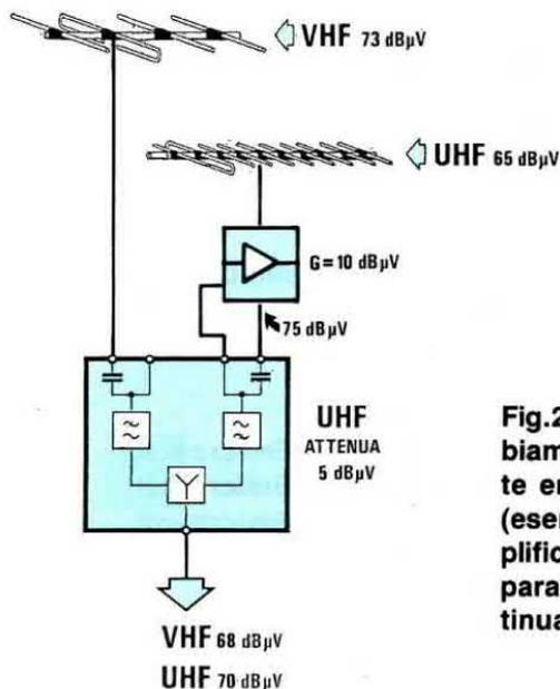
Fig.285 Se un segnale, prima di miscelarlo lo dobbiamo preamplificare, dovremo necessariamente entrare nell'ingresso VHF + 12 o UHF + 12 V (esempio in figura). Internamente, sia il preamplificatore che il miscelatore provvederanno a separare il segnale VHF o UHF dalla tensione continua dei 12 volt.
