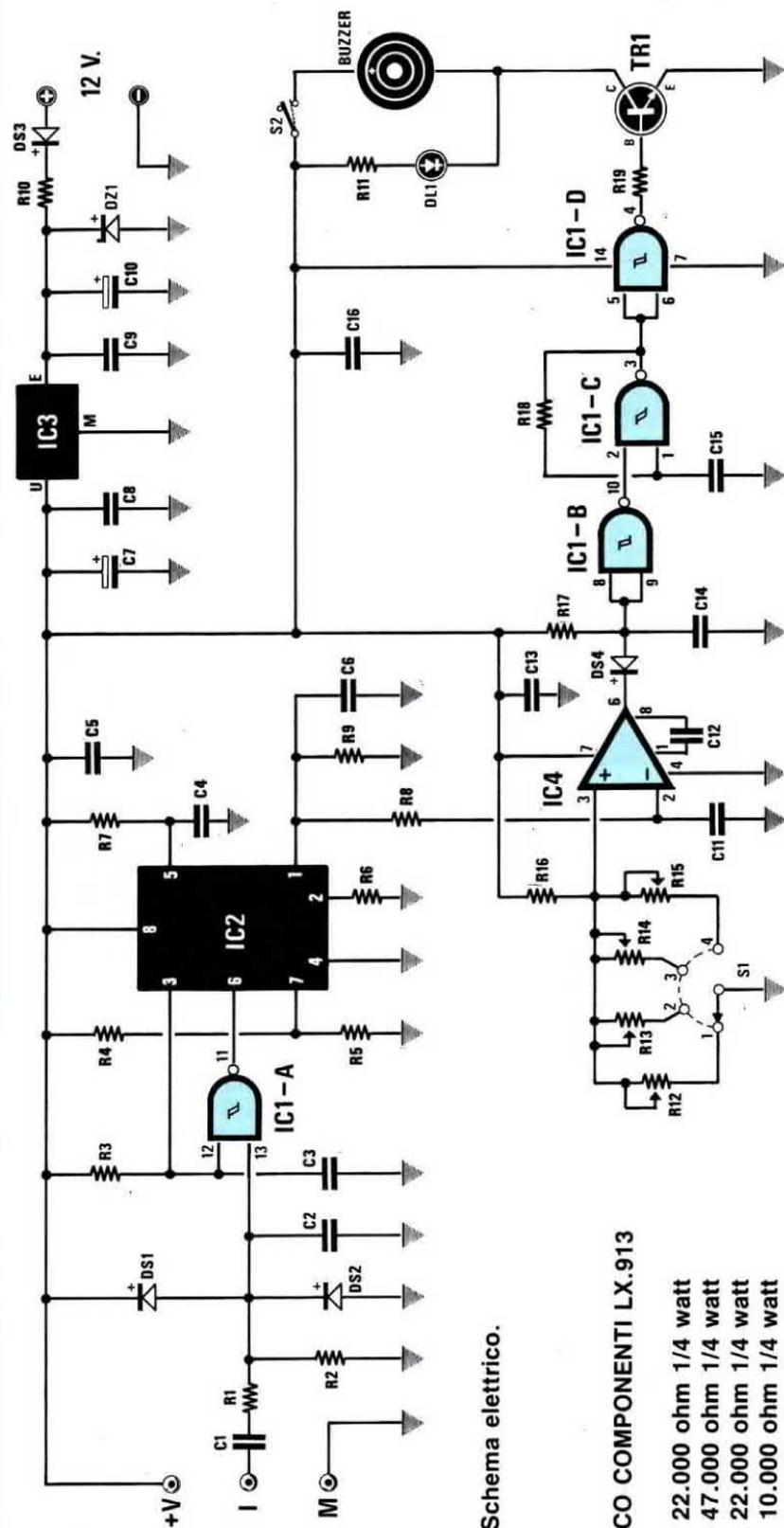
Fig. 1 Schema elettrico.
