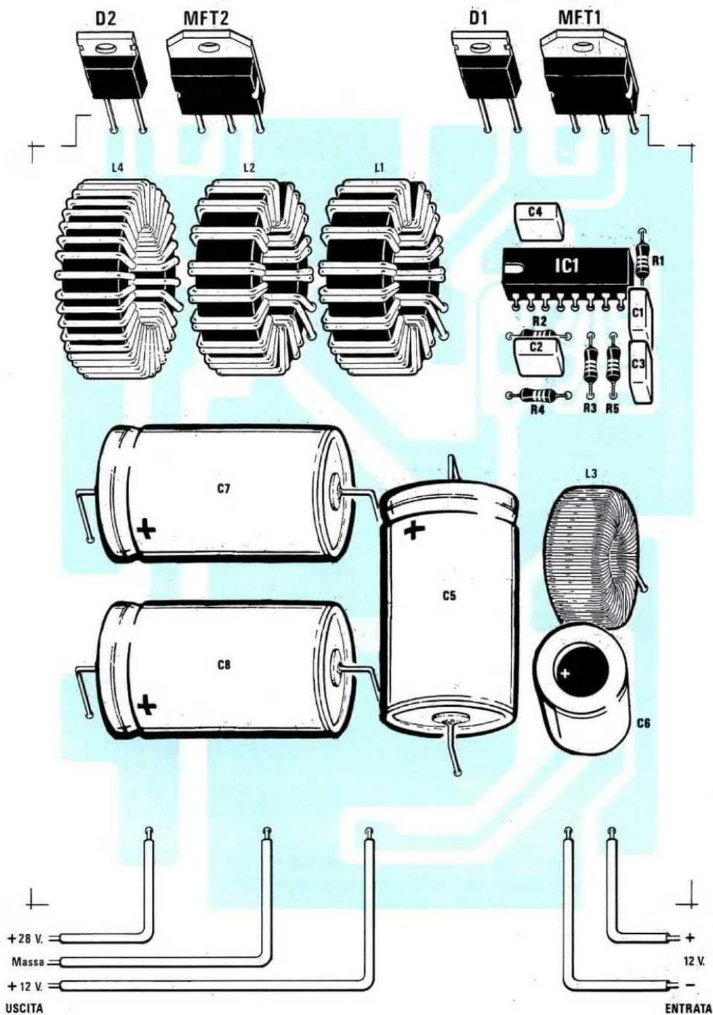
**Fig.3** Schema pratico di montaggio dell'elevatore di tensione. Le induttanze utilizzate per ottenere la extratensione dei 28 volt portano le sigle L1-L2. Si notino nello schema i due Mos-Power MFT1 e MFT2 utilizzati come "interruttori" e i due diodi D1 e D2 necessari per impedire che il condensatore elettrolitico C7 si scarichi, quando una delle due bobine risulterà cortocircuitata a massa.
