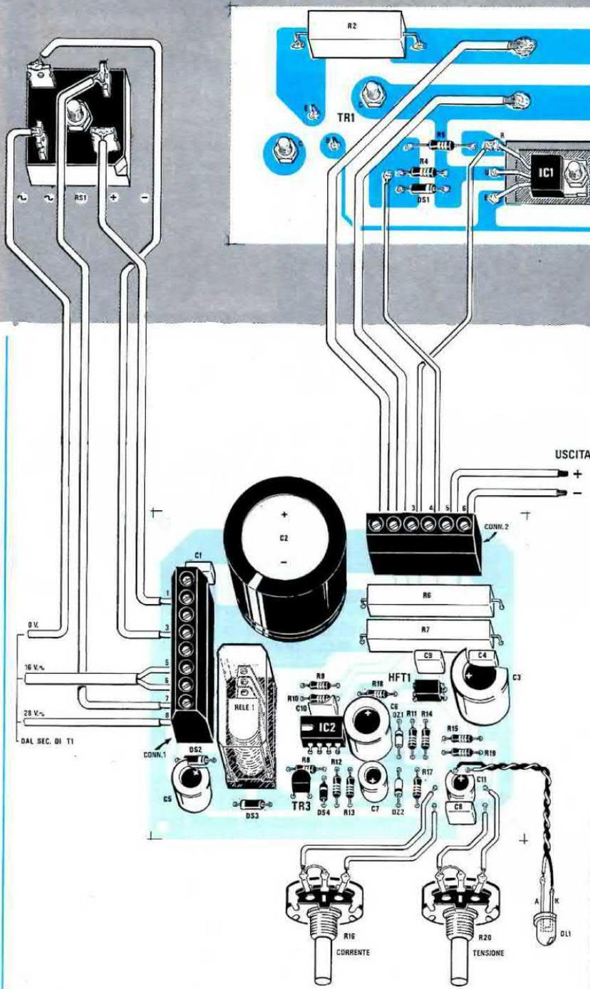
**Fig.8** In questo disegno potete vedere i collegamenti da effettuare per collegare il circuito stampato base LX.897 con il circuito LX.898 fissato sull'aletta posteriore del mobile. Sul lato destro di tale aletta fissate anche il ponte raddrizzatore da 25 amper. Si noti la mica posta sotto all'integrato IC1.
