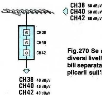
Fig.270 Se abbiamo tre segnali che ci giungono con tre diversi livelli, utilizzando un filtro con tre celle sintonizzabili separatamente potremo equalizzarli ancor prima di applicarli sull'ingresso del preamplificatore.
