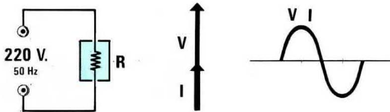
Fig.3 Applicando su una linea alternata un carico puramente "resistivo", la tensione e la corrente rimangono sempre in fase.
