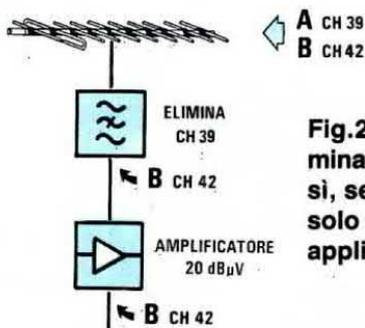
Fig.268 Un filtro elimina canale può risultare utile per eliminare i segnali che un'antenna non dovrebbe captare. Così, se in un'antenna prescelta ed installata per ricevere il solo canale 42, dovesse entrare un residuo del canale 39, applicando questo filtro, lo elimineremmo totalmente.
