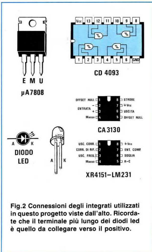
Fig.2 Connessioni degli integrati utilizzati in questo progetto viste dall'alto. Ricordate che il terminale più lungo dei diodi led è quello da collegare verso il positivo.
