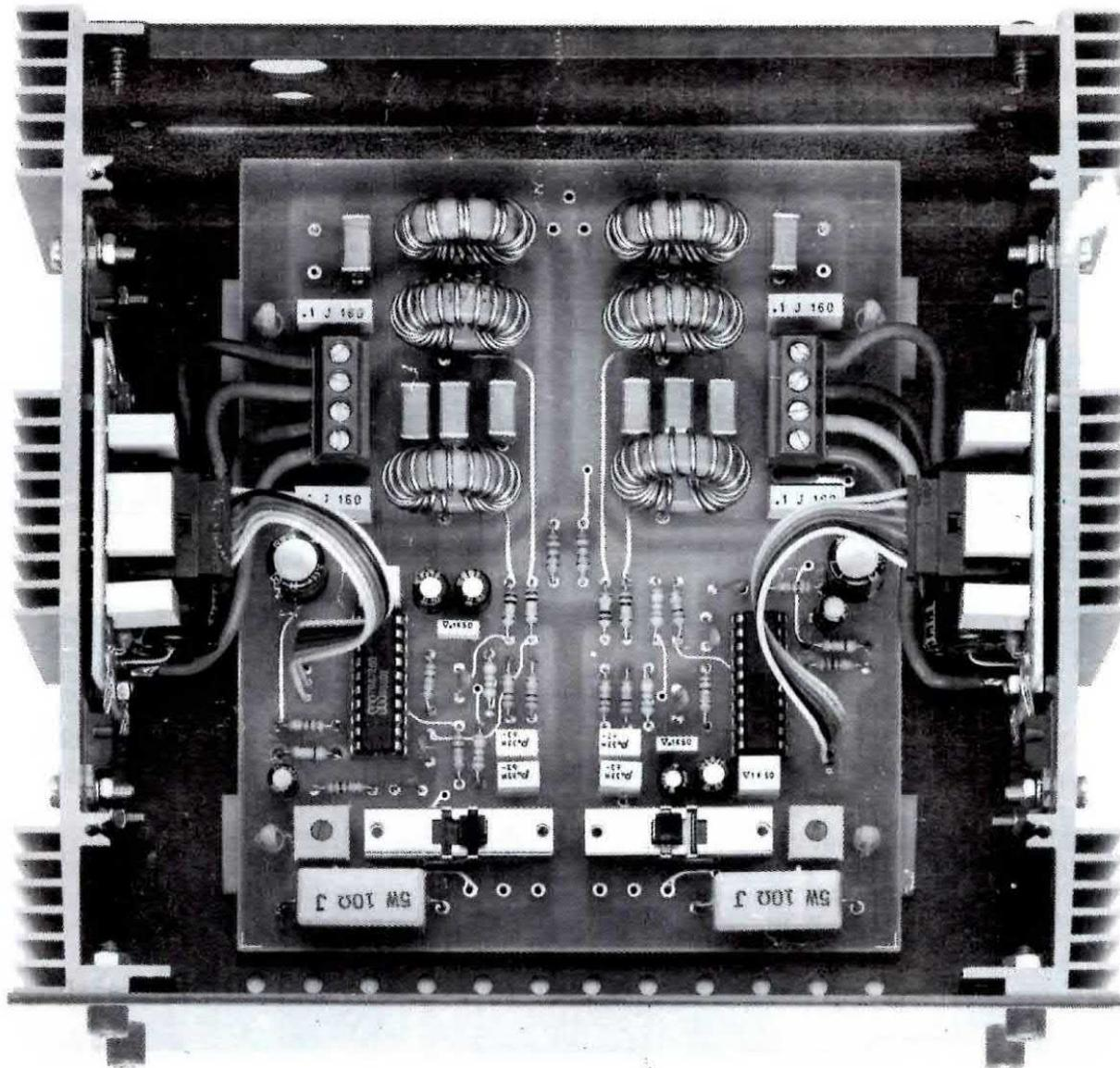
**Fig.13** In questa foto potete vedere come viene disposto il circuito stampato base LX.910 all'interno del mobile. Sulle due alette laterali del mobile applicherete i due circuiti stampati LX.911, non dimenticando di isolare il corpo dei quattro Mos-Power con le miche e le rondelle isolanti.
