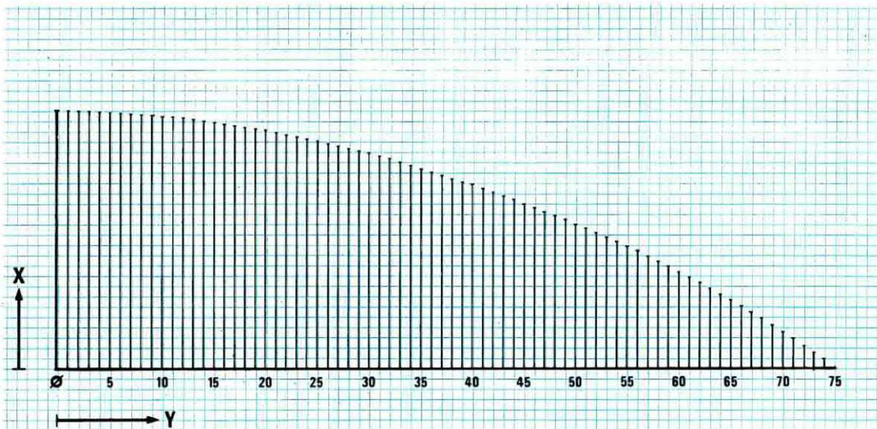
**Fig.10** Per tracciare il profilo di una parabola, una volta determinato il valore da assegnare a "C" (profondità al centro), si dovrà calcolare, partendo da questo punto e per ogni centimetro, l'altezza "X" fino ad arrivare all'estremità del raggio. A calcoli ultimati vi ritroverete sulla carta un disegno simile a quello visibile in questa figura.
