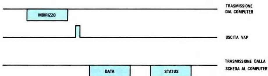
**Fig.8** Diagramma temporale di sola Trasmissione (MODO 3). In questa configurazione la scheda funziona solo come "trasmettitore", cioè la parola di indirizzo inviata dal computer verso la scheda, una volta riconosciuta, la abilita a trasmettere verso il computer gli ingressi di DATA INPUT e STATUS INPUT.
