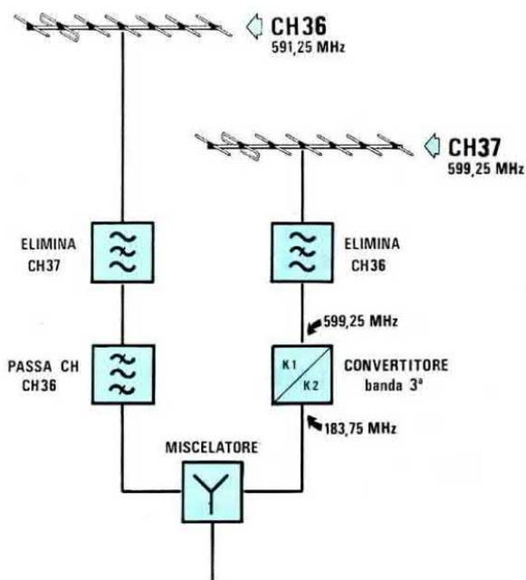
**Fig.289** Sulla linea di discesa del canale 36 applicheremo subito un filtro elimina-canale 37 seguito da un filtro passa-canale 36, in modo da non lasciare passare nessun residuo del canale 37. Sulla linea di discesa del canale 37 applicheremo un filtro elimina-canale 36, poi convertiremo questo segnale UHF sul canale 37, in "banda 3°".
