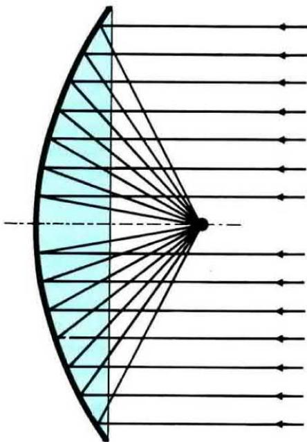
**Fig.8** Se il profilo della parabola è perfetto, il suo "guadagno" risulterà massimo, perchè il segnale captato dalla sua superficie verrà interamente convogliato sull'esatto punto focale.
