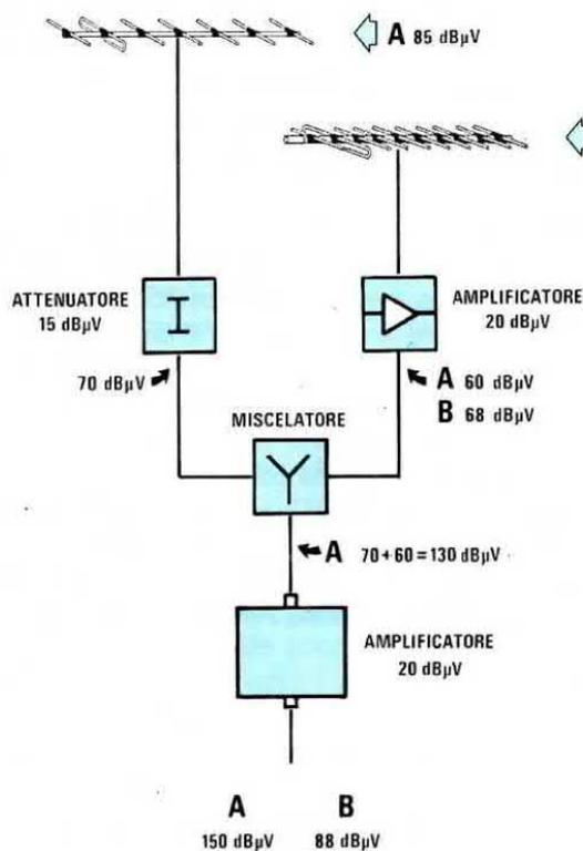
Fig.254 Non sempre la soluzione presentata in fig.253 può risultare soddisfacente. Infatti, se il segnale della emittente A (Ch.39) giunge fortissimo, è facile che l'antenna per l'emittente B (Ch.42) capti del segnale residuo di A. Questo residuo, preamplificato dall'amplificatore, si sommerà al segnale captato dall'antenna A, per cui sull'uscita finale non ci ritroveremo più con  $60 \text{ dBmicrovolt}$  bensì con  $150 \text{ dBmicrovolt}$ .
