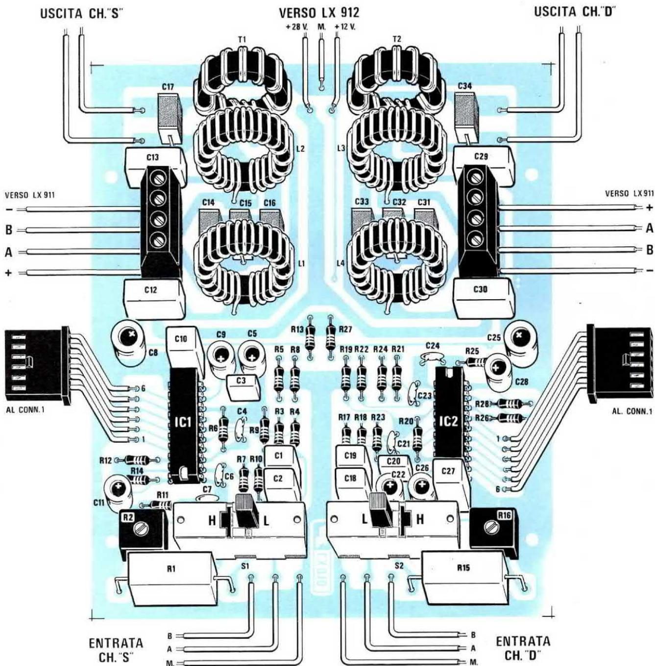
Fig. 12 Schema pratico di montaggio dell'amplificatore Stereo 64 + 64 Watt. I connettori femmina a 6 fili disegnati ai lati dello stampato, andranno innestati nei due connettori maschi presenti sullo stampato LX.911 (vedi fig.10). Anche i fili - B A + che escono dalle due morsettiere andranno a collegarsi a tale stampato. In alto al centro, i tre fili di alimentazione, 28 volt, Massa, 12 volt, che preleverete dal kit LX.912.
