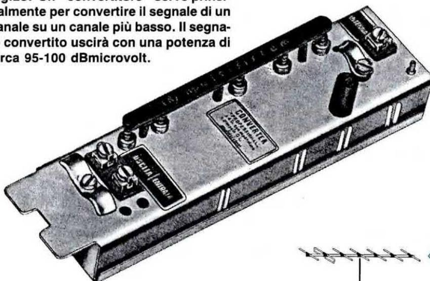
**Fig.288** Se nella vostra zona giungono due canali adiacenti tanto forti da disturbarsi a vicenda e non riuscite ad eliminare tale difetto nemmeno inserendo nelle linee di discesa dei filtri elimina-canale, vi converrà convertirne uno su un diverso canale.
