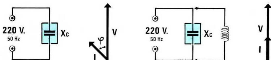
**Fig.13** Se un carico "capacitivo" applicato su una linea sfasa la corrente in "anticipo", per riportarla in fase sarà sufficiente applicare in parallelo una induttanza in grado di sfasare in ritardo gli stessi gradi.
