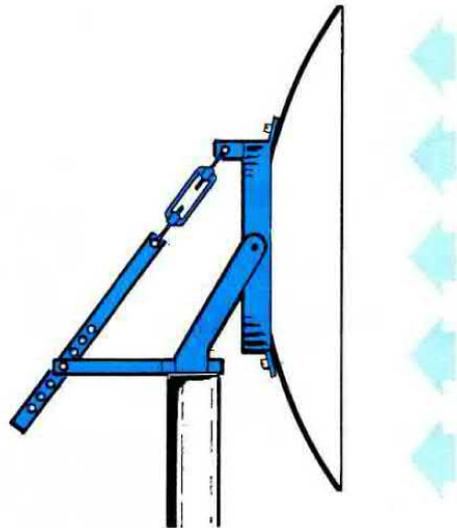
**Fig.15** Per evitare queste oscillazioni è necessario usare dei supporti che riescano ad abbracciare almeno metà parabola ed in più punti della sua circonferenza. Nella fig.16 vi indichiamo come potrebbe essere costruito un simile supporto.
