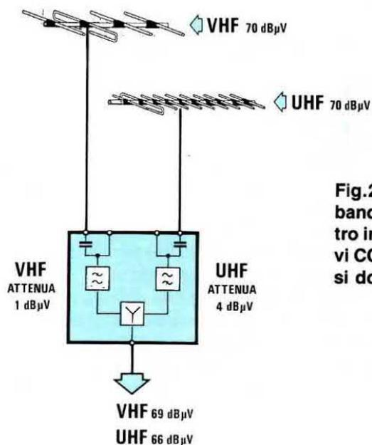
Fig.283 Nei miscelatori esiste sempre per ogni banda un "duplice" ingresso, uno isolato e l'altro in cui risultano invece presenti 12 volt positivi CC. Per accoppiare direttamente due antenne si dovranno scegliere i due ingressi "isolati".
