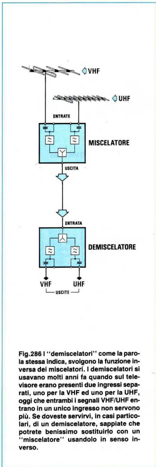
Fig.286 I "demiscelatori" come la parola stessa indica, svolgono la funzione inversa dei miscelatori. I demiscelatori si usavano molti anni fa quando sul televisore erano presenti due ingressi separati, uno per la VHF ed uno per la UHF, oggi che entrambi i segnali VHF/UHF entrano in un unico ingresso non servono più. Se doveste servirvi, in casi particolari, di un demiscelatore, sappiate che potrete benissimo sostituirlo con un "miscelatore" usandolo in senso inverso.
