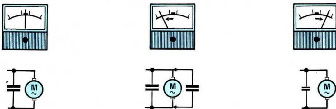
**Fig.17** Se alimentando un motore o un qualsiasi carico induttivo notate che la lancetta rimane al "centro scala", significa che la linea risulta rifasata. Se, invece, la lancetta devia verso sinistra, la capacità inserita risulta insufficiente, quindi dovrete aggiungere un secondo condensatore. Se devia verso destra, dovrete ridurre il valore della capacità del condensatore.
