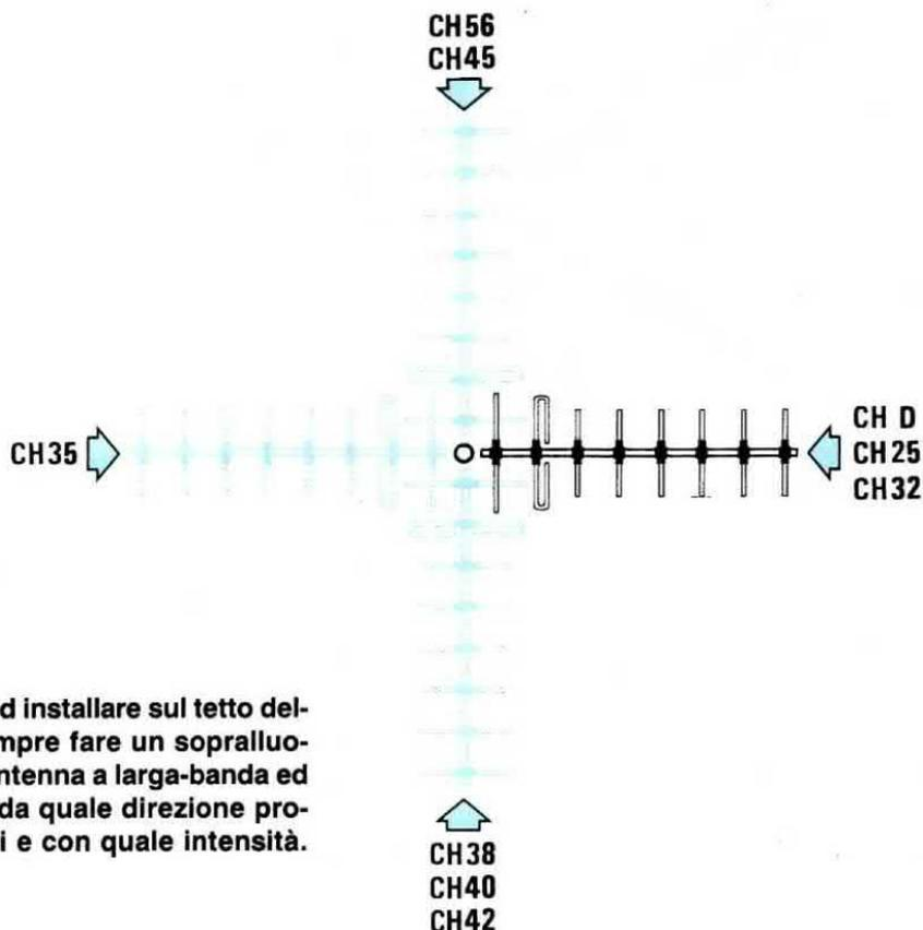
**Fig.292** Prima di iniziare ad installare sul tetto delle antenne, conviene sempre fare un sopralluogo e controllare con un'antenna a larga-banda ed un Misuratore di campo da quale direzione provengono i diversi segnali e con quale intensità.
