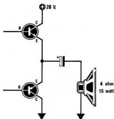
**Fig.3** Raddoppiando la tensione di alimentazione, sempre lasciando collegato un altoparlante da 4 ohm, riuscirete ad aumentare la potenza in uscita e a raggiungere così circa 15 watt. Anche se si utilizzano dei finali da 100 watt, in uscita si otterrà sempre una potenza di 15 watt.
