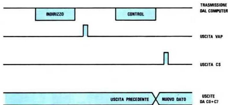
**Fig.6** Diagramma temporale di sola Ricezione (MODO 1). Inviando dal computer alla linea seriale una sequenza costituita da una parola di "indirizzo" e da una di "controllo", il VAP (Valid Address Pulse) ci confermerà che la scheda l'ha ricevuta e riconosciuta ed il CS (Command Strobe) che la parola di controllo è disponibile.
