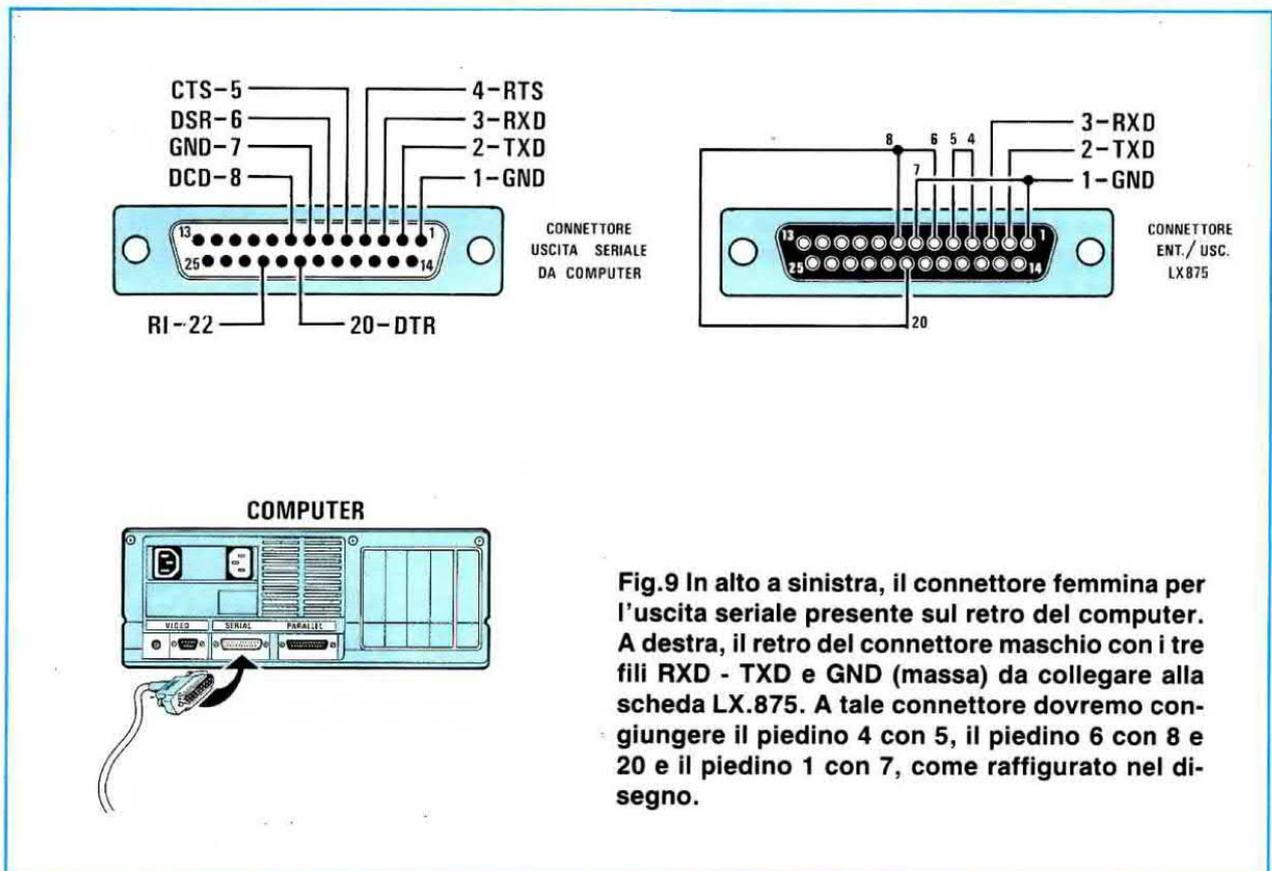
Fig.9 In alto a sinistra, il connettore femmina per l'uscita seriale presente sul retro del computer. A destra, il retro del connettore maschio con i tre fili RXD - TXD e GND (massa) da collegare alla scheda LX.875. A tale connettore dovremo congiungere il piedino 4 con 5, il piedino 6 con 8 e 20 e il piedino 1 con 7, come raffigurato nel disegno.
