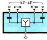
Fig.280 Un miscelatore a larga-banda permette di miscelare qualsiasi segnale MF - VHF - UHF partendo da un minimo di 80 MHz fino ad un massimo di 900 MHz circa. I segnali miscelati usciranno attenuati di circa 4 dB.
