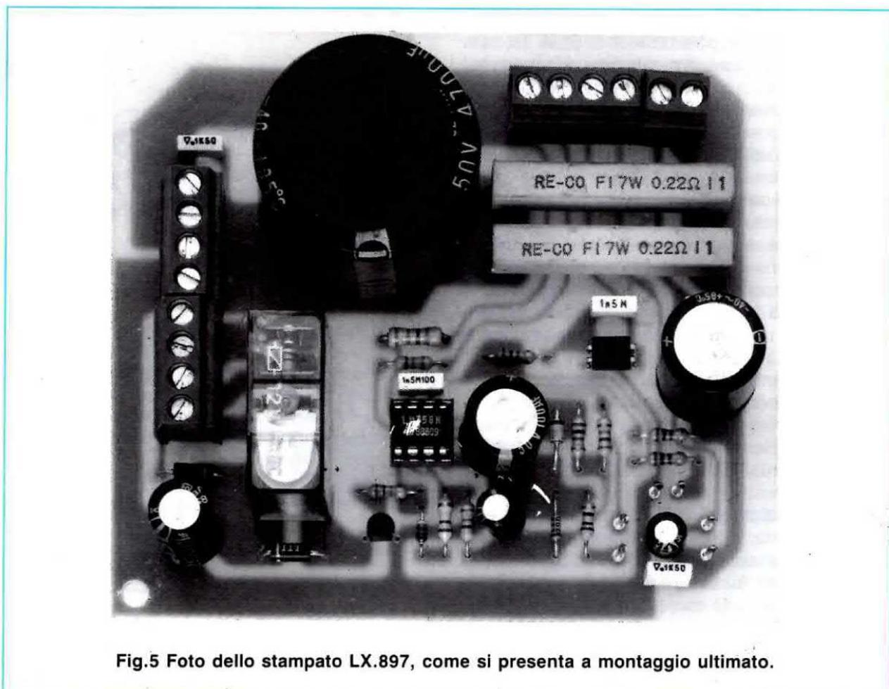
Fig.5 Foto dello stampato LX.897, come si presenta a montaggio ultimato.
