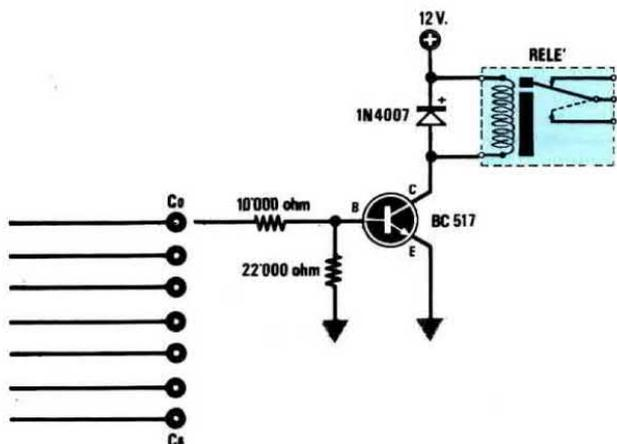
Fig.11 Per eccitare dei relè da 12 volt, potremo collegare alle uscite da C0 a C6 un transistor darlington BC.517. Ogni scheda è idonea per pilotare 7 relè.
