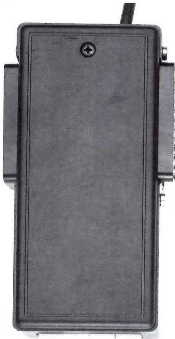
**Fig.1** Il progetto è composto da una piccola scatola in plastica con due prese Scart femmina fisse e una spina Scart maschio volante. Premendo uno dei quattro pulsanti otterrete tutte le combinazioni necessarie per gestire due Videoregistratori o per passare il segnale di un Videogioco su un monitor o su un televisore, ed anche per collegare, senza dover spostare delle prese, il nostro ricevitore per satelliti TV sulla presa SCART nei televisori che già ne dispongono.
