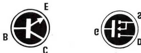
Fig.2 Per i Primi Passi vi proponiamo questo semplice tester in grado di provare, oltre a tutti i tipi di Transistor, anche i Mospower. Utilizzando un Mospower, il Gate lo inserirete nella boccola B, il Drain nella boccola C ed il Source nella boccola E.
