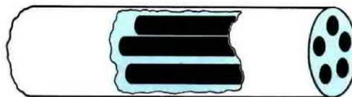
**Fig.1** Quel sottile filo di stagno usato nel montaggio di circuiti elettronici, contiene dei minuscoli canaletti pieni di disossidante. Questa sostanza se fusa sul punto da saldare, provvede a "bruciare" la sottile pellicola di ossido presente su ogni superficie.
