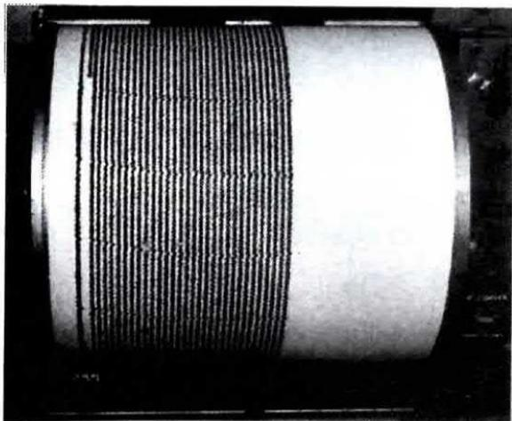
**Fig.5** In tutti i sismografi si usa un "pennino" che appoggia su un foglio di carta avvolta attorno un tamburo di un certo diametro in perenne rotazione. Oltre al costo proibitivo di tali stampanti, abbiamo pure notato che quando si verifica un terremoto, il sismogramma da esse prodotto sormonta le righe adiacenti rendendo difficoltosa la lettura. Nel nostro sismografo appare la sola traccia del sisma completa della data, dell'ora e dei minuti (vedi fig.7).
