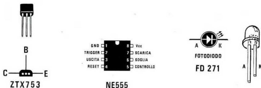
Fig.4 Connessioni del transistor ZTX.753 visto da sotto e dell'NE.555 visto da sopra.
