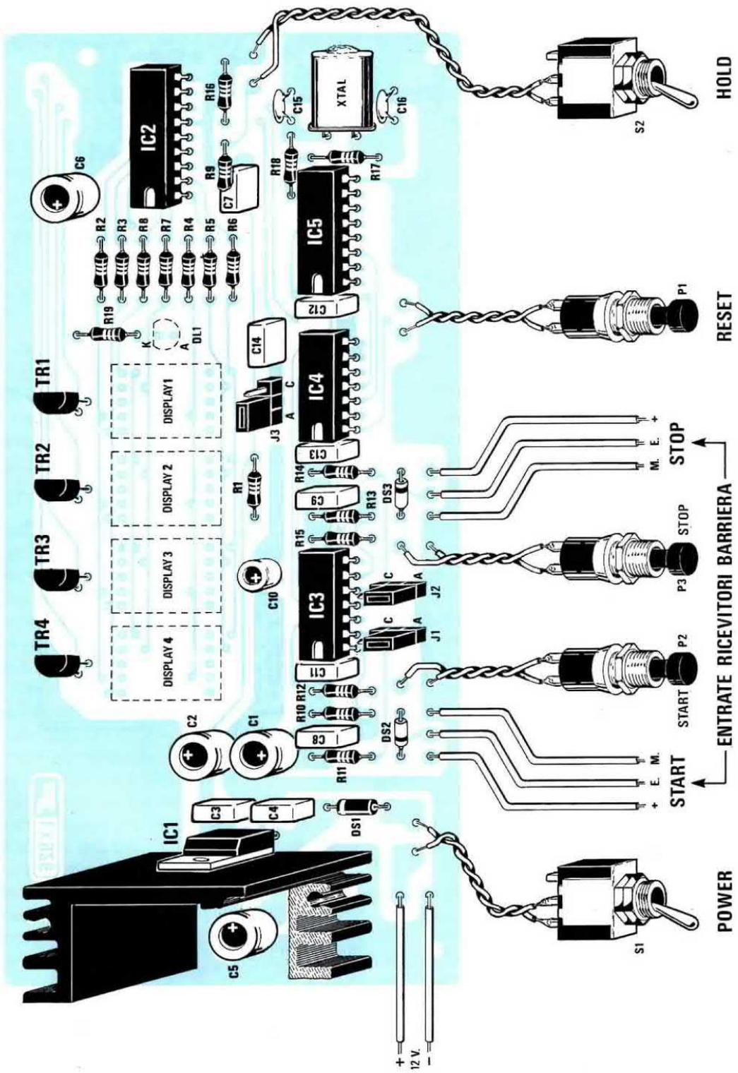
Fig. 11 Schema pratico dello stadio contatore LX.926 con già collegati tutti i componenti esterni allo stampato. Si noti la posizione in cui risultano innestati gli spinotti di cortocircuito sui connettori J1-J2-J3. I display ed il diodo DL1 andranno inseriti dal lato opposto dello stampato (vedi foto di fig.13).
