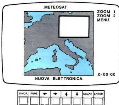
**Fig.18** Il vantaggio che offre tale scheda è quello di registrare una immagine già ricevuta, pertanto se vi interessa registrare una zona diversa della stessa immagine, potrete spostare la finestra dello Zoom, premere ENTER e poi il tasto FRECCIA in SU. Ricordate che fino a quando non sentirete un Beep, la registrazione non sarà completata. Il tempo di registrazione di una PAGINA si aggira sui "3 minuti".
