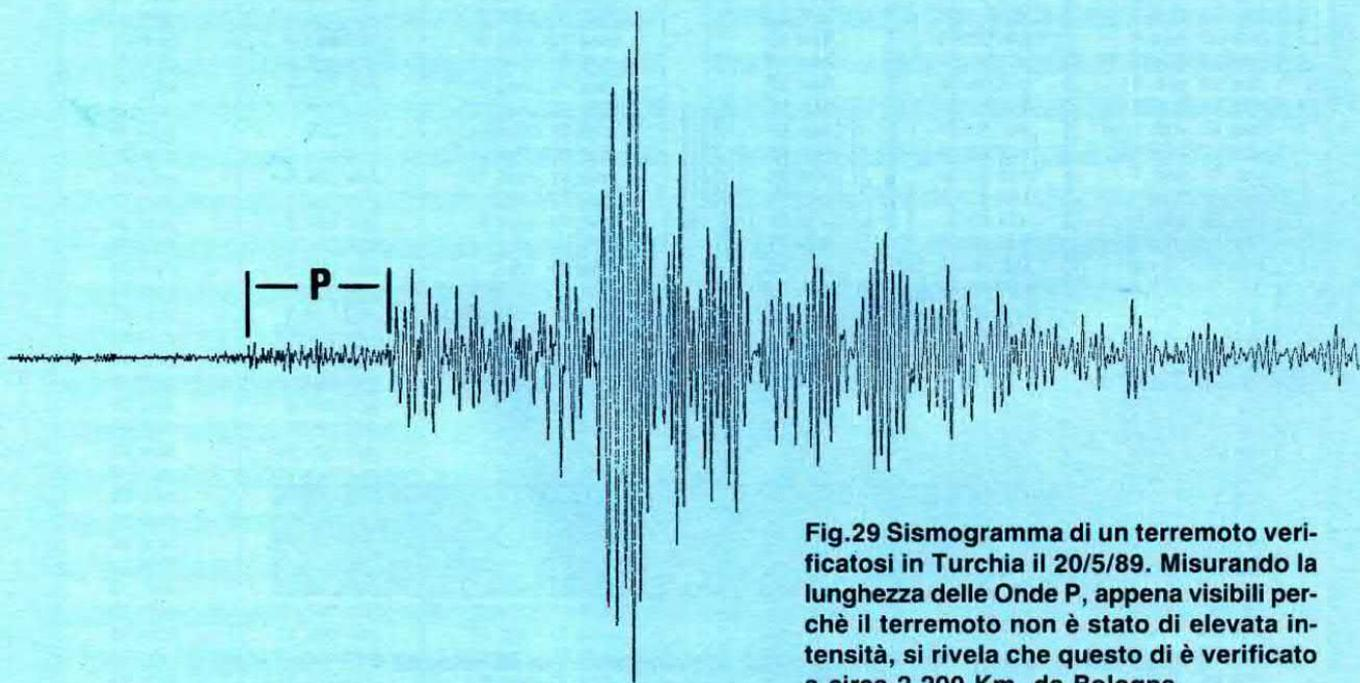
**Fig.29 Sismogramma di un terremoto verificatosi in Turchia il 20/5/89. Misurando la lunghezza delle Onde P, appena visibili perchè il terremoto non è stato di elevata intensità, si rivela che questo di è verificato a circa 2.200 Km. da Bologna.**
