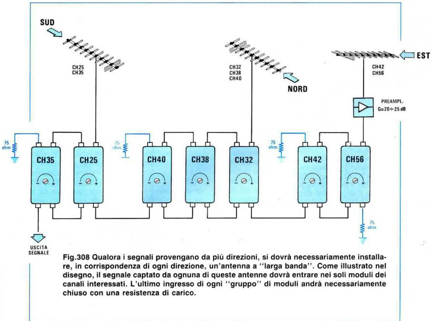
**Fig.308** Qualora i segnali provengano da più direzioni, si dovrà necessariamente installare, in corrispondenza di ogni direzione, un'antenna a "larga banda". Come illustrato nel disegno, il segnale captato da ognuna di queste antenne dovrà entrare nei soli moduli dei canali interessati. L'ultimo ingresso di ogni "gruppo" di moduli andrà necessariamente chiuso con una resistenza di carico.
