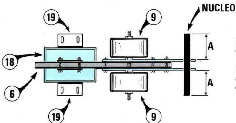
Fig.33 Parte finale del braccio del pendolo vista da sopra. Si noti la vaschetta dell'olio, i due Pesi ed il nucleo ferroxcube appoggiato sulle due basette di vetronite.
