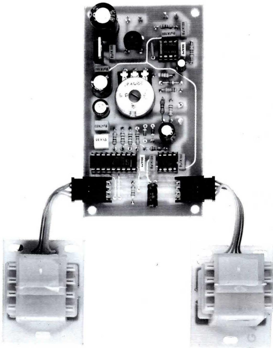
**Fig.11** Come noterete, i terminali delle due bobine risultano "sfalsati", quindi si innestano nel circuito stampato solo nel giusto verso. Il nucleo ferrocube si muoverà senza attrito all'interno dei fori di questi due rocchetti.
