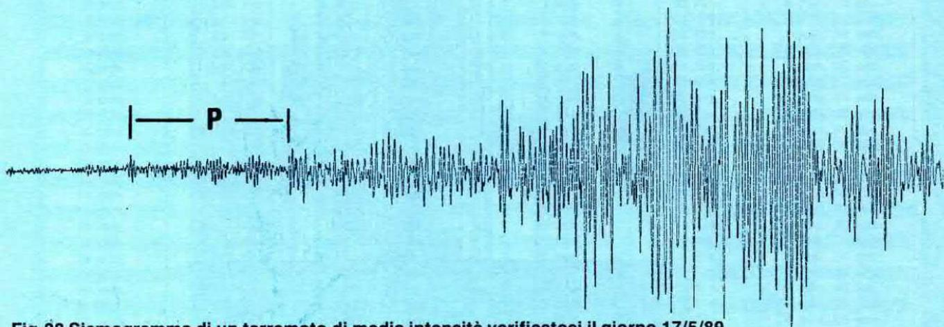
**Fig.28 Sismogramma di un terremoto di media intensità verificatosi il giorno 17/5/89 a circa 4.500 Km. da Bologna. Tale terremoto, forse perchè non ha provocato danni o vittime, non è stato menzionato nè dalla radio nè dalla televisione. Precisiamo che possono passare anche uno o due settimane senza che si registri un terremoto, ma che è anche possibile che se ne verifichino tre o quattro nello stesso giorno.**
