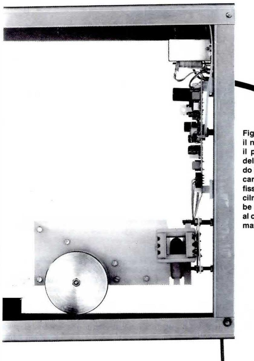
**Fig.29** Come vedesi in questa foto, il nucleo ferroxcube dovrà risultare il più possibile centrato all'interno del rocchetto della bobina. Spostando i dadi delle viti che servono a bloccare i circuiti stampati su cui sono fissate queste due bobine, potrete facilmente centrare il nucleo ferroxcube all'interno del foro. Si noti sopra al circuito stampato LX.922 il trasformatore di alimentazione.
