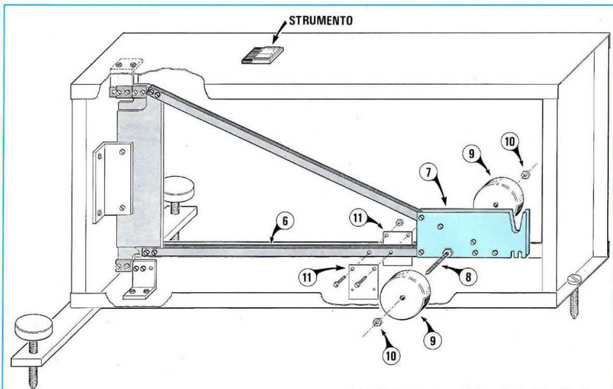
**Fig.26** Sul perno n.8 inserirete i due Pesi n.9 che fisserete con i dadi n.10 senza stringerli eccessivamente. I due lamierini dell'ammortizzatore n.11 conviene fissarli al braccio n.6 solo dopo aver fissato la vaschetta dell'olio (vedi fig.27).
