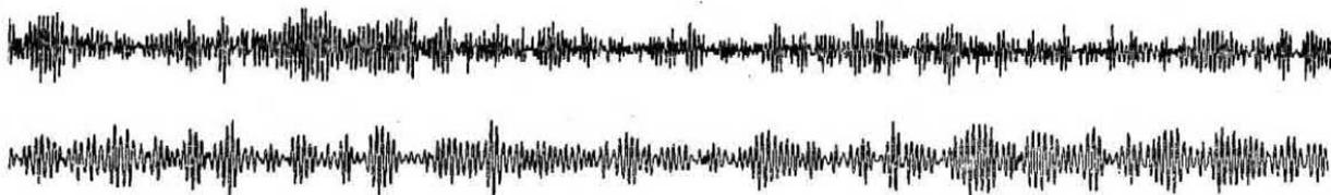
**Fig.5** I sismogrammi provocati da variazioni della pressione atmosferica, da mareggiate, assestamenti del sottosuolo, ecc., si presentano con caratteristiche ben diverse da quelle di un terremoto. Infatti, le oscillazioni sono d'ampiezza molto ridotta e durano per ore e ore, anche per uno o due giorni consecutivi.
