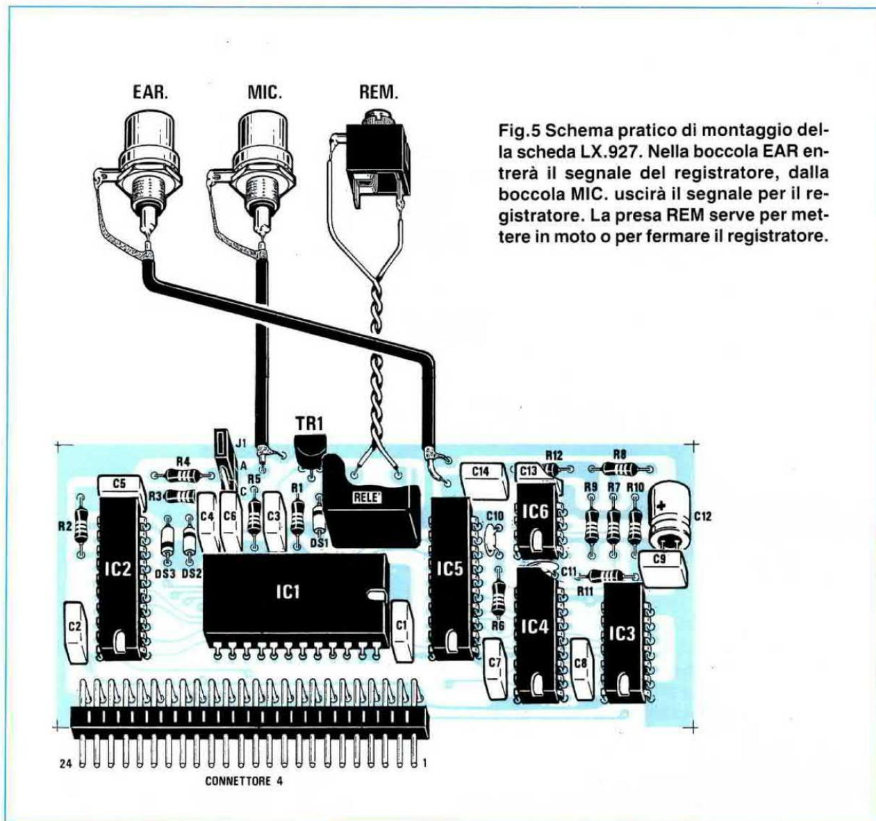
Fig.5 Schema pratico di montaggio della scheda LX.927. Nella boccia EAR entrerà il segnale del registratore, dalla boccia MIC. uscirà il segnale per il registratore. La presa REM serve per mettere in moto o per fermare il registratore.
