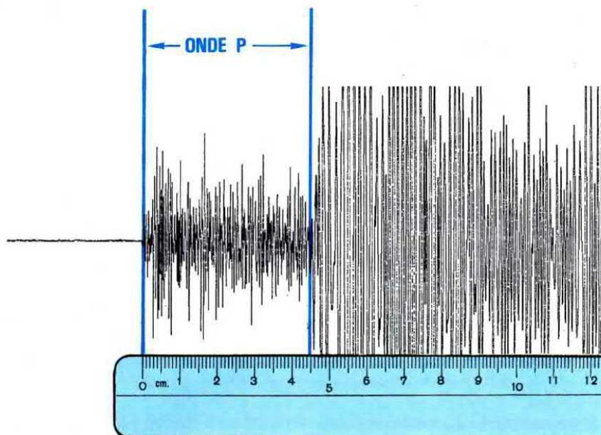
**Fig.30** Per determinare con buona approssimazione la distanza a cui si è verificato il sisma che abbiamo registrato, senza dover eseguire calcoli complicati, potremo misurare con un righello la lunghezza del tracciato delle "onde P", poi vedere, in base alla velocità della stampante, nella tabella a fianco a quanti chilometri corrispondono. Nell'esempio riportato troveremo che 44 mm. corrispondono a una distanza di 7.300 Km. (velocità 5mm. per minuto).
