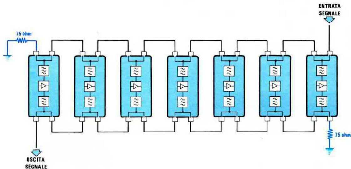
**Fig.301** Il motivo per cui su ogni modulo sono presenti due ingressi e due uscite si può intuire da tale disegno. Il segnale captato dall'antenna che entra nell'ultimo modulo di destra, tramite il secondo ingresso potrà raggiungere tutti gli altri moduli. Lo stesso dicasi per il prelievo sulle uscite dei segnali preamplificati. La prima uscita (modulo di destra) e l'ultimo ingresso (modulo di sinistra) andranno "chiusi" con un carico antiinduttivo da 75 ohm.
