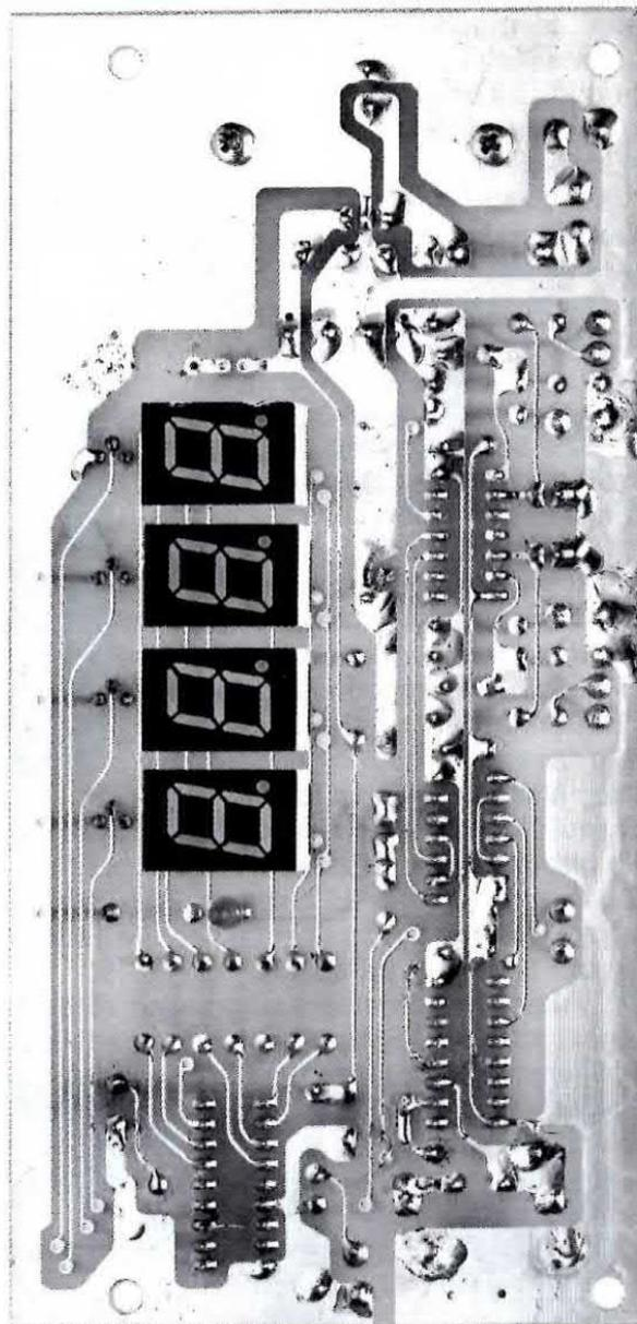
Fig. 13 Dal lato opposto di tale circuito stampato andranno posti i quattro display, rivolendo il punto decimale presente sul lato destro del n.8 verso il basso. Il circuito stampato a fori metallizzati vi verrà fornito completo di disegno serigrafico.
