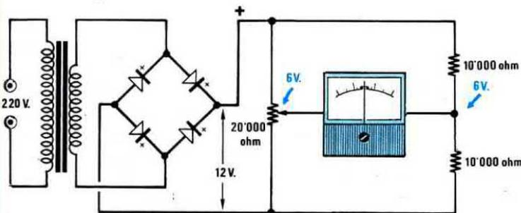
**Fig.2** Il nucleo ferrocube può essere paragonato al "cursore" di un potenziometro collegato come vedesi in figura. Se il cursore risulta centrato, la lancetta dello strumento rimane sullo "0", se invece si sposta verso l'alto o verso il basso, la lancetta devierà verso sinistra o verso destra.
