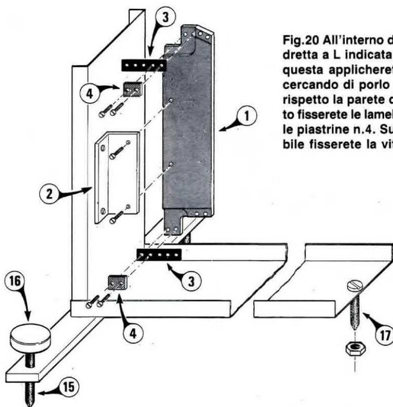
**Fig.20** All'interno del mobile fisserete la squadretta a L indicata con il numero 2 e sopra a questa applicherete il supporto fresato n.1, cercando di porlo perfettamente in parallelo rispetto la parete del mobile. Su tale supporto fisserete le lamelle n.3, che bloccherete con le piastrine n.4. Sulla parte anteriore del mobile fisserete la vite a punta n.17.
