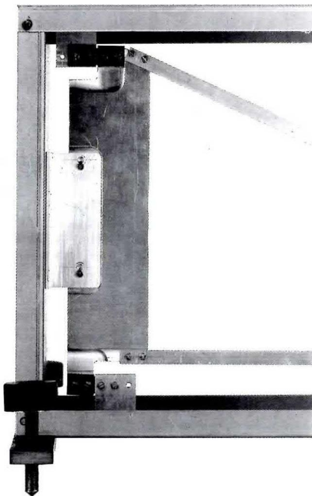
barra inserirete le due viti a **passo fine n.15**, necessarie per il livellamento e sulle quali avrete già fissato le manopole **n.16**.
