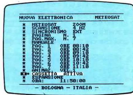
**Fig.14** Portare il cursore in corrispondenza della riga CASSETTA ATTIVA e premere il tasto ENTER. Il cursore dovrà rimanere "necessariamente" sulla riga "Casetta Attiva".
