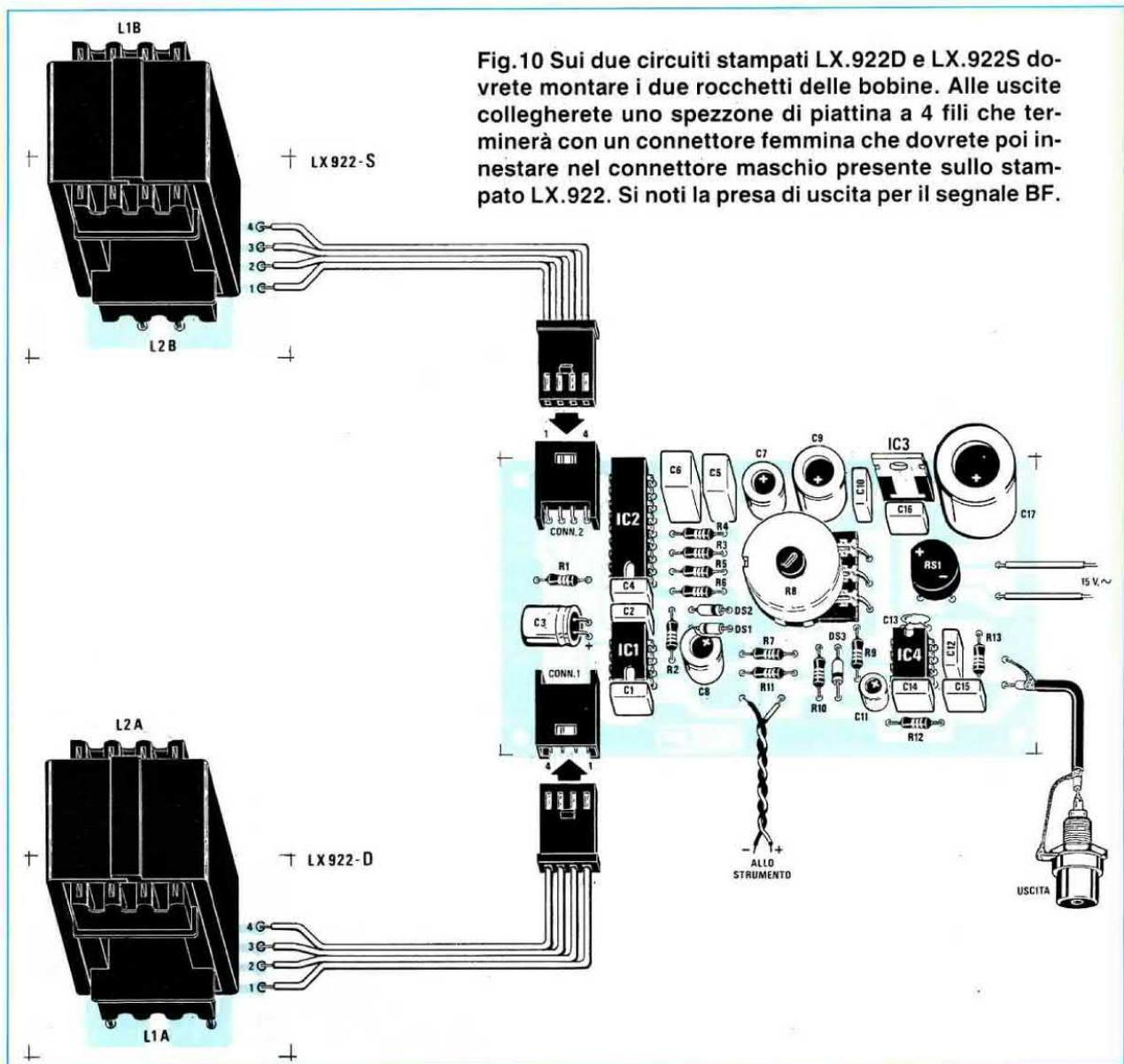
Fig.10 Sui due circuiti stampati LX.922D e LX.922S dovrete montare i due rocchetti delle bobine. Alle uscite collegherete uno spezzone di piattina a 4 fili che terminerà con un connettore femmina che dovrete poi innestare nel connettore maschio presente sullo stampato LX.922. Si noti la presa di uscita per il segnale BF.
