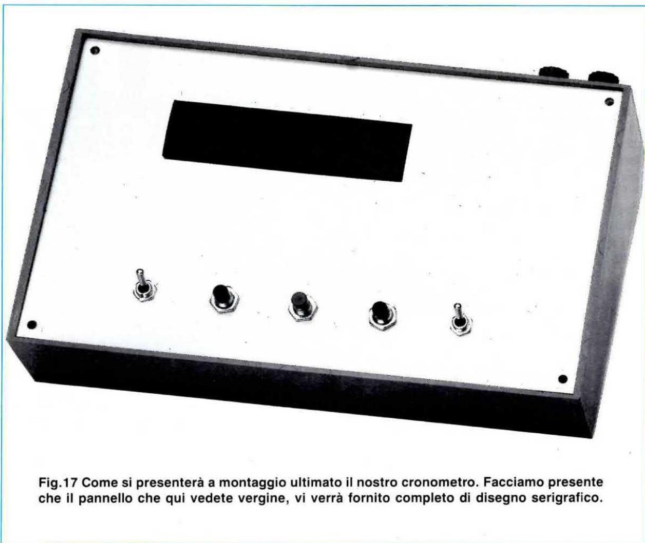
**Fig.17** Come si presenterà a montaggio ultimato il nostro cronometro. Facciamo presente che il pannello che qui vedete vergine, vi verrà fornito completo di disegno serigrafico.
