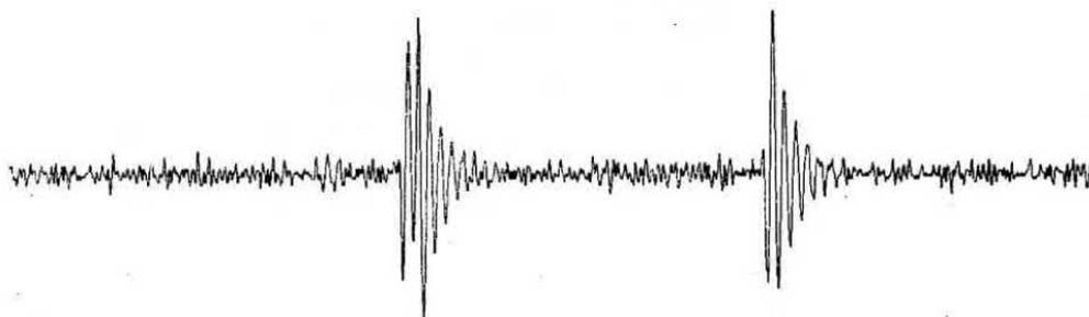
Fig.41 Passando a circa mezzo metro dal sismografo, vedrete apparire sulla carta delle sinusoidi che, dopo 4-5 oscillazioni, si attenueranno. Se questo si verifica il vostro sismografo sarà già idoneo a rivelare qualsiasi sisma. L'ampiezza delle sinusoidi dipenderà dalla sensibilità a cui avrete regolato i due potenziometri presenti in tale circuito.
