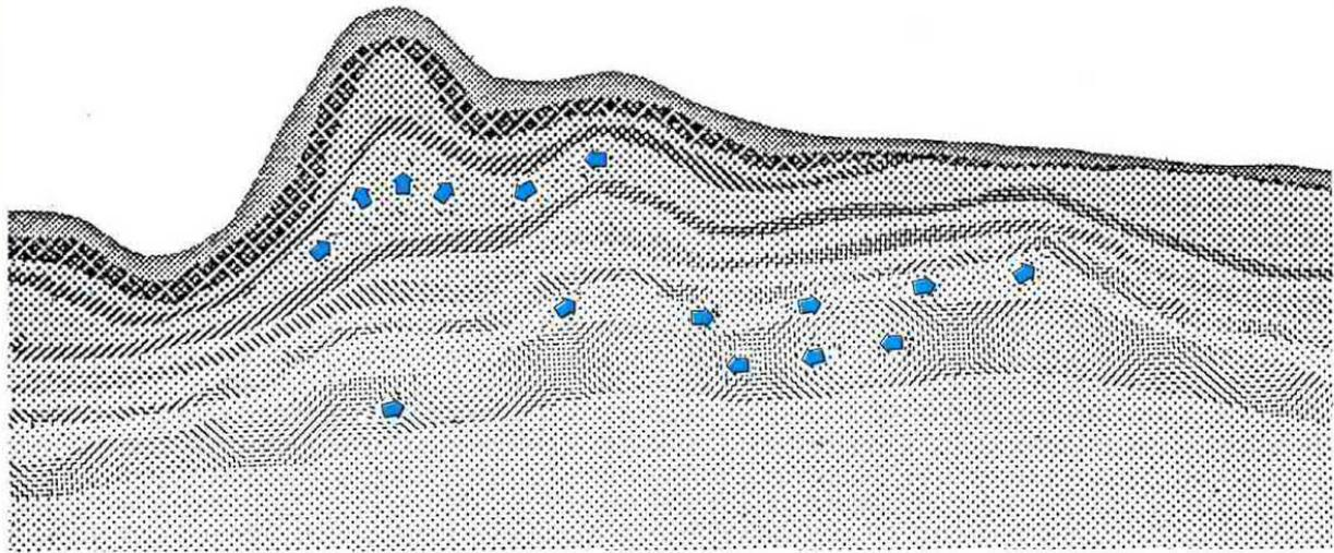
**Fig.10** Gli strati della litosfera in continuo movimento, comprimono altri strati. Pertanto gli strati superiori, se elastici possono sollevarsi dando origine a catene montuose, se rigidi possono resistere fino al limite di "rottura", dando luogo in un secondo tempo ad un improvviso rilascio di energia che fa vibrare la crosta terrestre provocando il terremoto.
