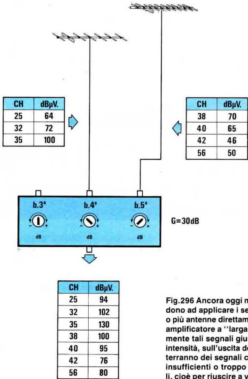
Fig.296 Ancora oggi molti installatori provvedono ad applicare i segnali TV captati da una o più antenne direttamente sugli ingressi di un amplificatore a "larga banda". Poichè difficilmente tali segnali giungeranno con la stessa intensità, sull'uscita del preamplificatore si otterranno dei segnali che potrebbero risultare insufficienti o troppo elevati. Per equalizzarli, cioè per riuscire a veder bene tutte le emittenti captabili, tale impianto andrebbe modificato come illustrato in fig.297.
