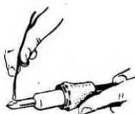
**Fig.2** Chi scioglie lo stagno sulla punta del saldatore, non riuscirà mai ad ottenere delle saldature perfette, perchè il disossidante in questo caso servirà solo per pulire la superficie del saldatore e non per "bruciare" l'ossido sulle superfici da saldare.
