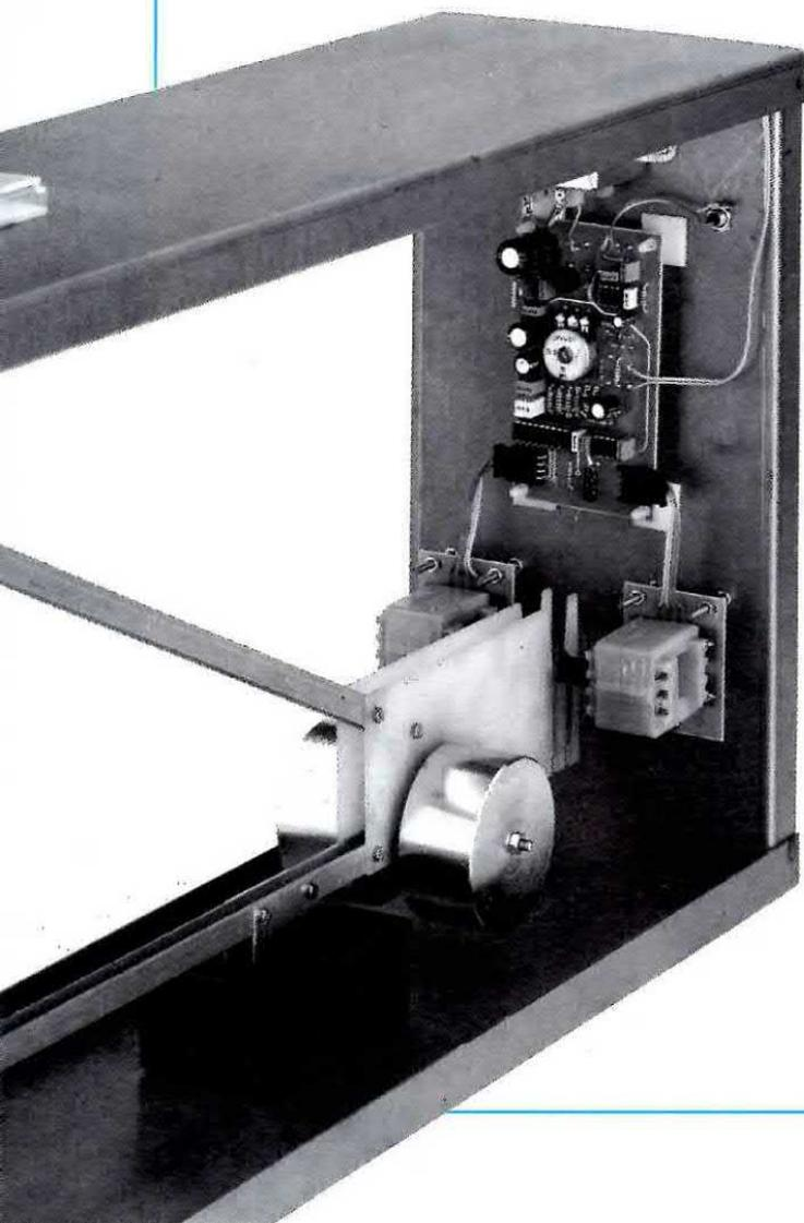
**Fig.27** In questa foto la parte anteriore del mobile vista internamente. Si noti il circuito stampato LX.922 fissato sul mobile con i distanziatori autoadesivi, le due bobine del sensore e la vaschetta in plastica contenente l'olio per l'ammortizzatore.
