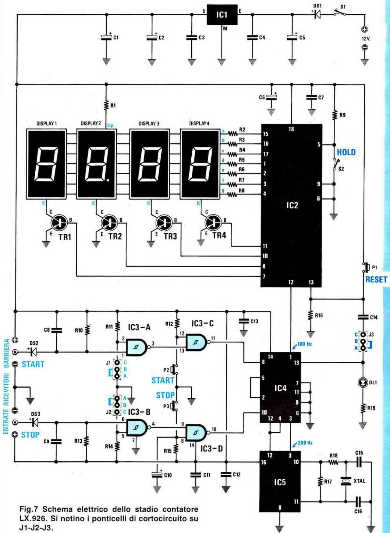
Fig.7 Schema elettrico dello stadio contatore LX.926. Si notino i ponticelli di cortocircuito su J1-J2-J3.
