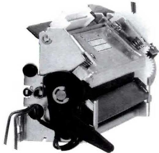
**Fig.14** Per inserire nella stampante la carta termica occorrerà abbassare la leva in plastica posta sul lato sinistro del corpo. Una volta inserita la carta, se non riporterete la leva nella sua posizione di lavoro, non riuscirete a stampare.
