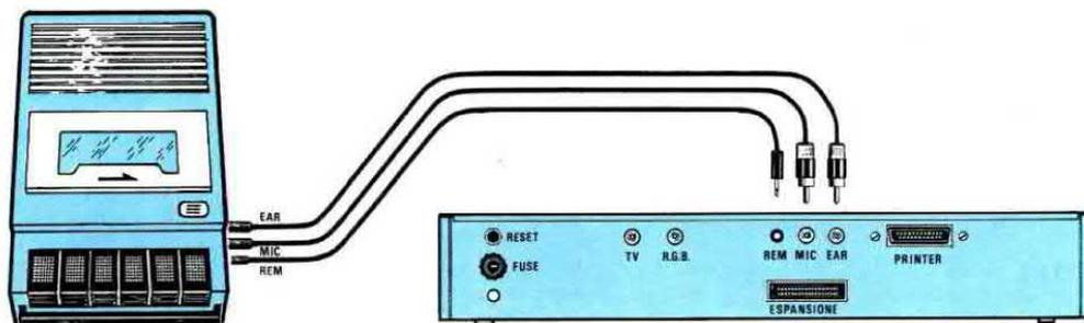
Fig.8 Nel retro del mobile del Videoconverter inserirete le due bocche MIC e EAR e la presa REM. **IMPORTANTE:** Non usate registratori provvisti di Controllo Automatico di Guadagno perchè questi, modificando automaticamente il livello dei grigi, determineranno sullo schermo la comparsa di immagini interamente "bianche".
