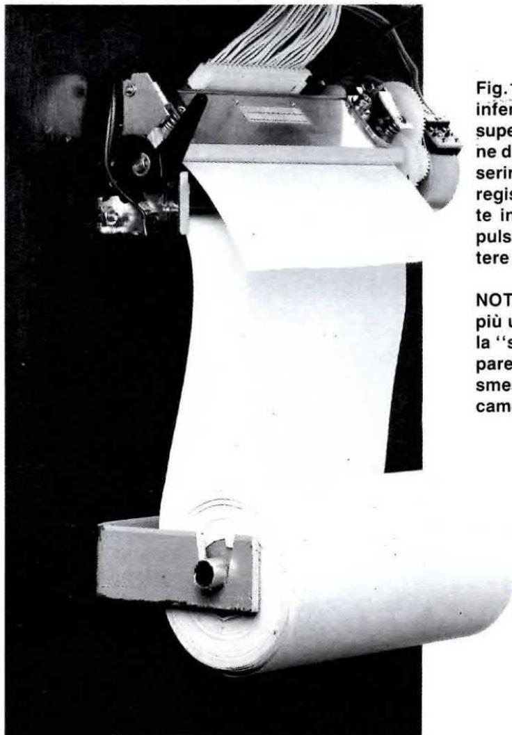
**Fig.15** La carta verrà inserita nella fessura inferiore e come noterete uscirà da quella superiore. Vi ricordiamo che la carta dispone di un solo lato sensibile, quindi se la inserirete in senso inverso non riuscirete a registrare alcun sismogramma. Se l'avrete inserita nel giusto verso, premendo il pulsante Reset vedrete apparire le due lettere NE.
