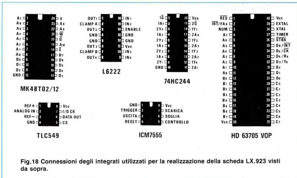
Fig.18 Connessioni degli integrati utilizzati per la realizzazione della scheda LX.923 visti da sopra.
