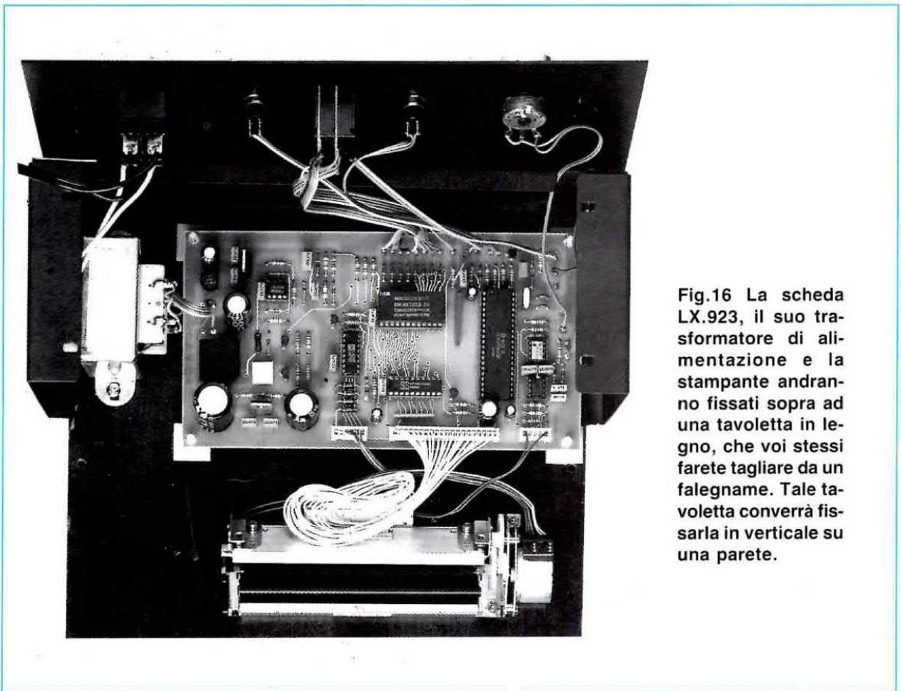
Fig.16 La scheda LX.923, il suo trasformatore di alimentazione e la stampante andranno fissati sopra ad una tavoletta in legno, che voi stessi farete tagliare da un falegname. Tale tavoletta converrà fissarla in verticale su una parete.
