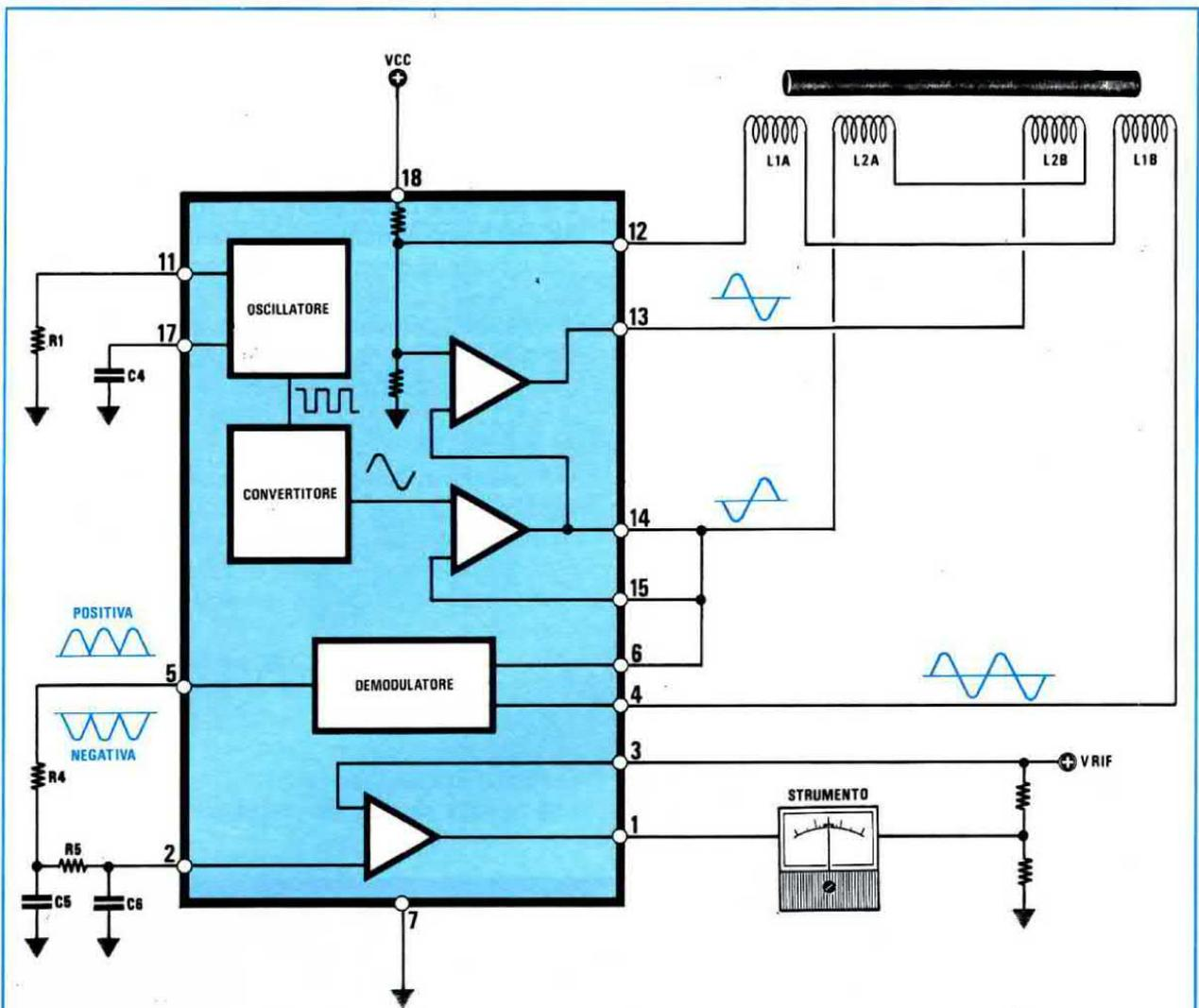
**Fig.1** Per realizzare il "sensore di movimento" abbiamo utilizzato un nucleo ferrocube che si muove all'interno di due coppie di bobine. L'integrato NE.5521 oltre a pilotare le due bobine eccitatrici L2, demodulerà il segnale captato dalle due bobine rivelatrici L1, così che ne ricaverete una tensione continua che provvederà a far deviare la lancetta dello strumento o verso destra o verso sinistra.
