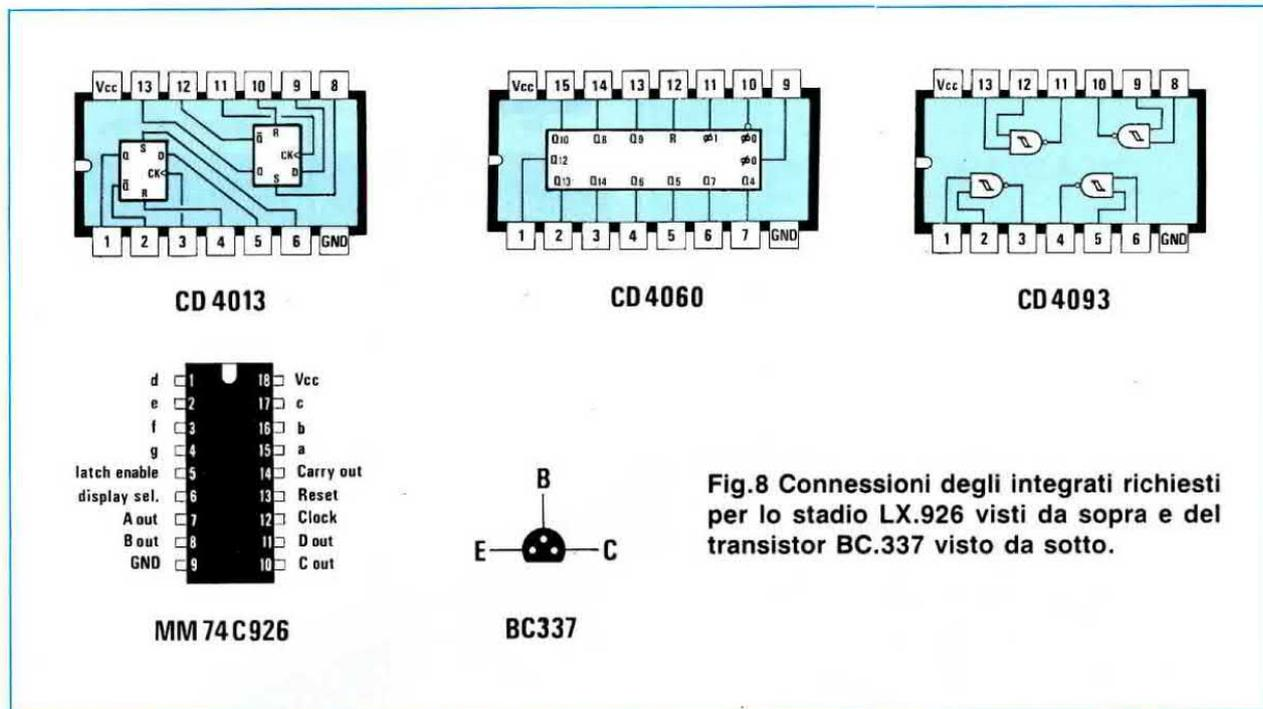
**Fig.8 Connessioni degli integrati richiesti per lo stadio LX.926 visti da sopra e del transistor BC.337 visto da sotto.**
