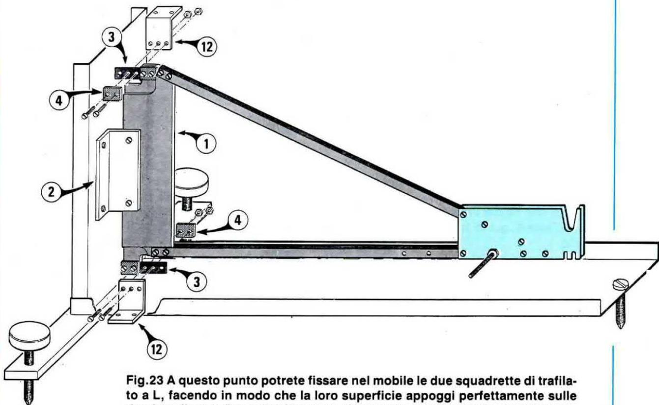
**Fig.23** A questo punto potrete fissare nel mobile le due squadrette di trafilato a L, facendo in modo che la loro superficie appoggi perfettamente sulle due lamelle n.3. Dopodichè potrete bloccare le lamelle con le piastrine n.4.
