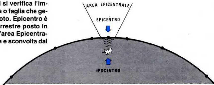
Fig.21 Se l'Ipocentro si trova a bassa profondità, cioè se il terremoto è del tipo "superficiale", l'area Epicentrale risulterà molto ridotta (vedi fig.20). Se l'Ipocentro si trova a grande profondità, aumenterà di conseguenza anche l'area Epicentrale come vedesi chiaramente in tale disegno. La scala Mercalli valuta gli effetti osservabili nell'area Epicentrale, la scala Richter la "potenza" scaturita nell'Ipocentro.
