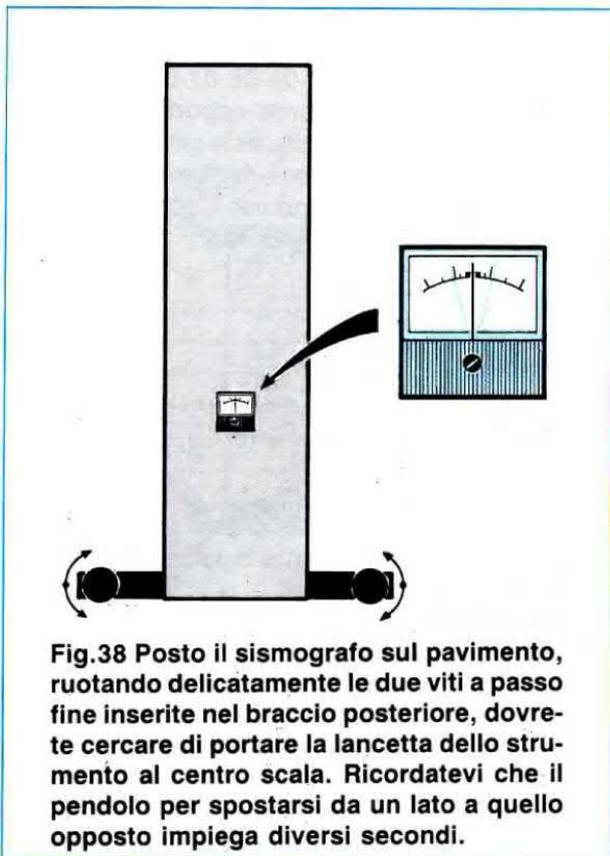
**Fig. 38** Posto il sismografo sul pavimento, ruotando delicatamente le due viti a passo fine inserite nel braccio posteriore, dovreste cercare di portare la lancetta dello strumento al centro scala. Ricordatevi che il pendolo per spostarsi da un lato a quello opposto impiega diversi secondi.
