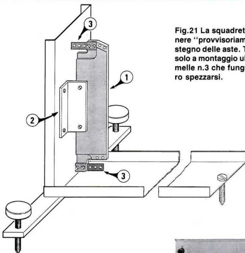
Fig.21 La squadretta a L n.2 serve per sostenere "provvisoriamente" il supporto per il sostegno delle aste. Tale squadretta andrà tolta solo a montaggio ultimato, diversamente le lamelle n.3 che fungono da cerniera potrebbero spezzarsi.
