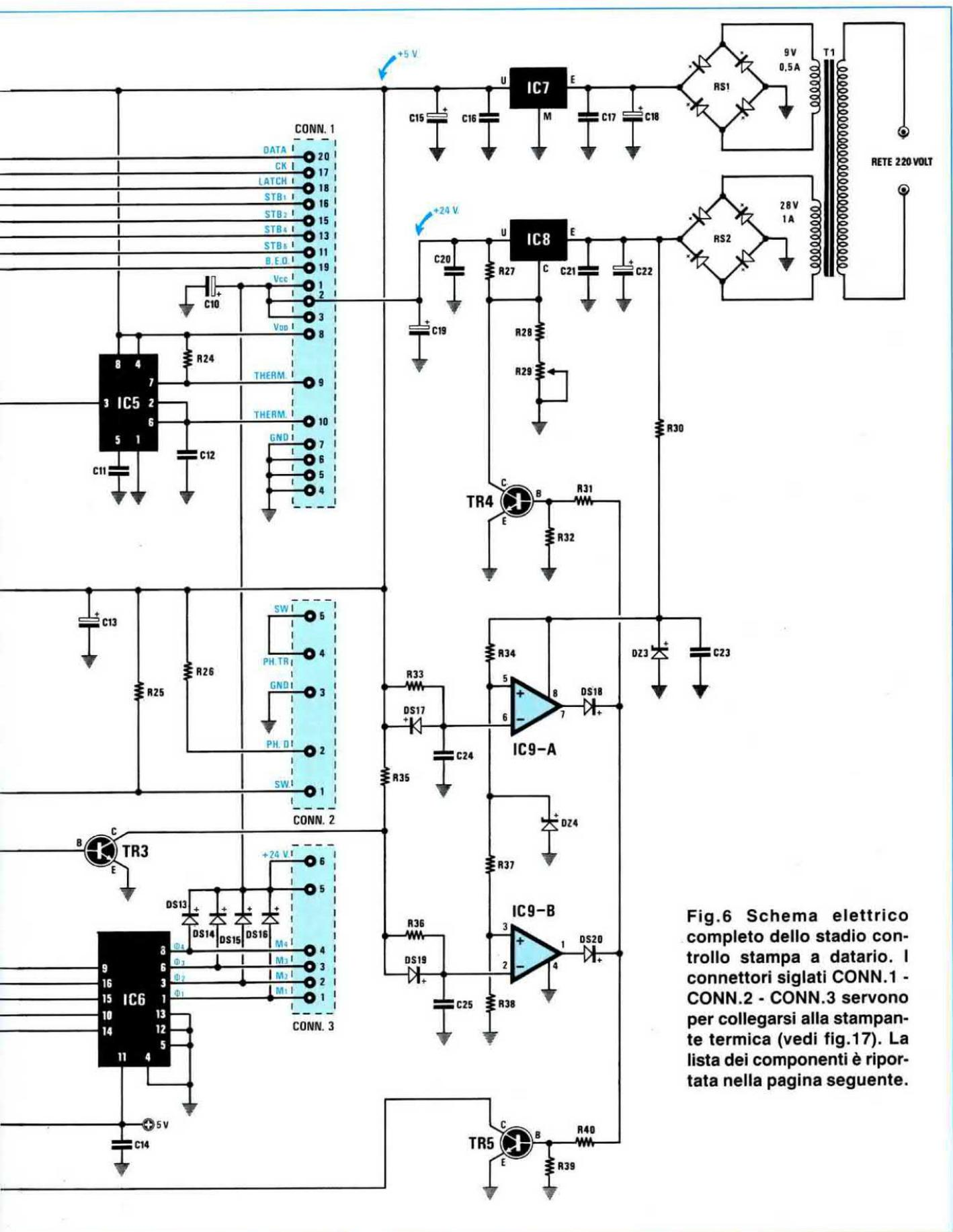
Fig.6 Schema elettrico completo dello stadio controllo stampa a datario. I connettori siglati CONN.1 - CONN.2 - CONN.3 servono per collegarsi alla stampante termica (vedi fig.17). La lista dei componenti è riportata nella pagina seguente.
