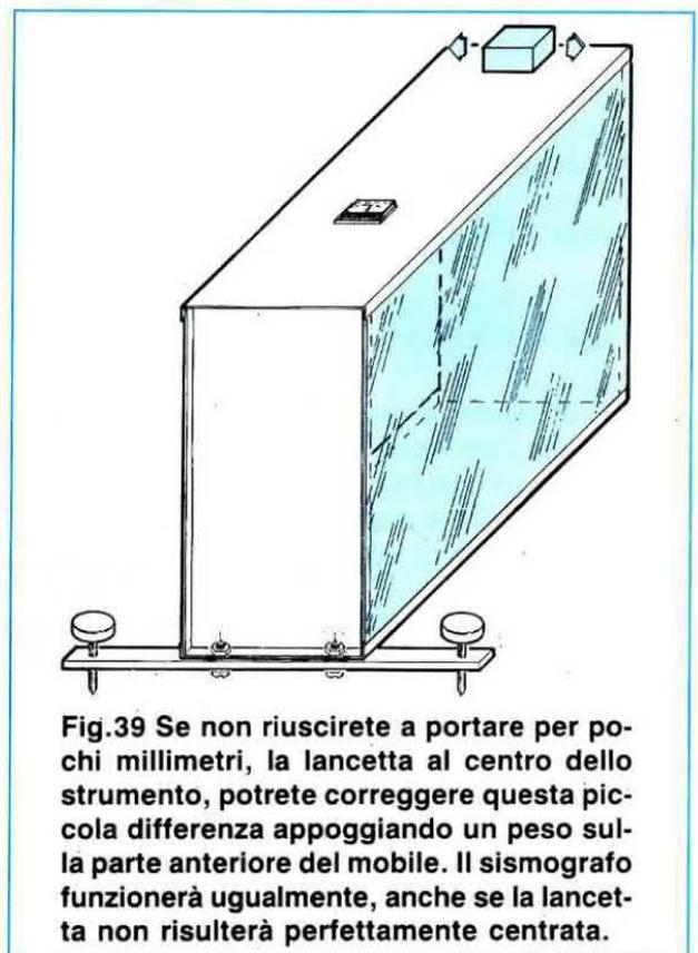
**Fig. 39** Se non riuscirete a portare per pochi millimetri, la lancetta al centro dello strumento, potrete correggere questa piccola differenza appoggiando un peso sulla parte anteriore del mobile. Il sismografo funzionerà ugualmente, anche se la lancetta non risulterà perfettamente centrata.
