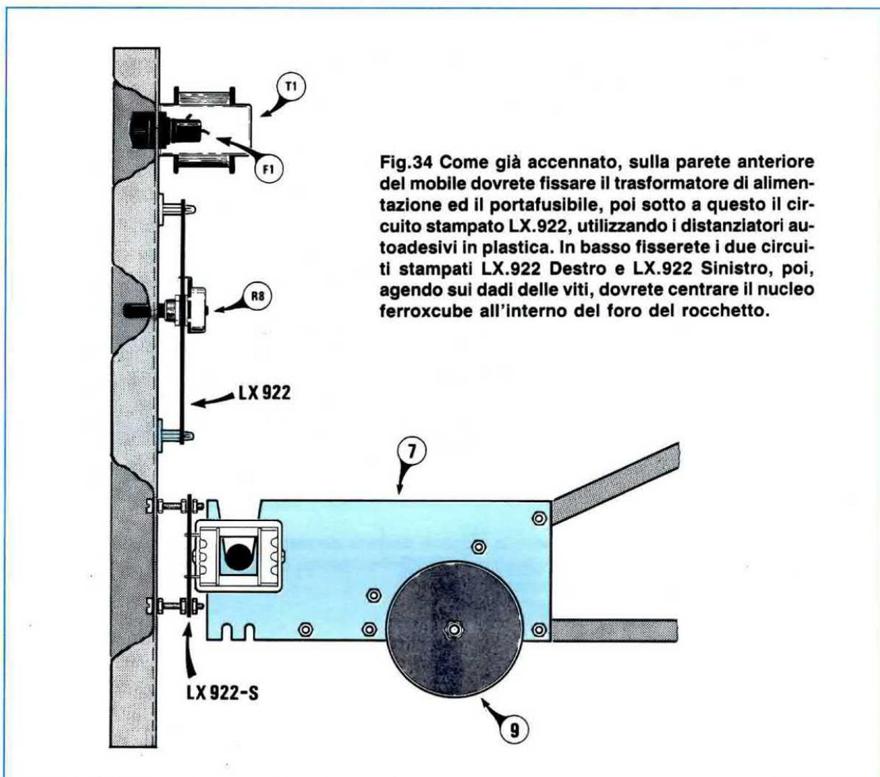
Fig.34 Come già accennato, sulla parete anteriore del mobile dovrete fissare il trasformatore di alimentazione ed il portafusibile, poi sotto a questo il circuito stampato LX.922, utilizzando i distanziatori autoadesivi in plastica. In basso fisserete i due circuiti stampati LX.922 Destro e LX.922 Sinistro, poi, agendo sui dadi delle viti, dovrete centrare il nucleo ferroxcube all'interno del foro del rocchetto.
