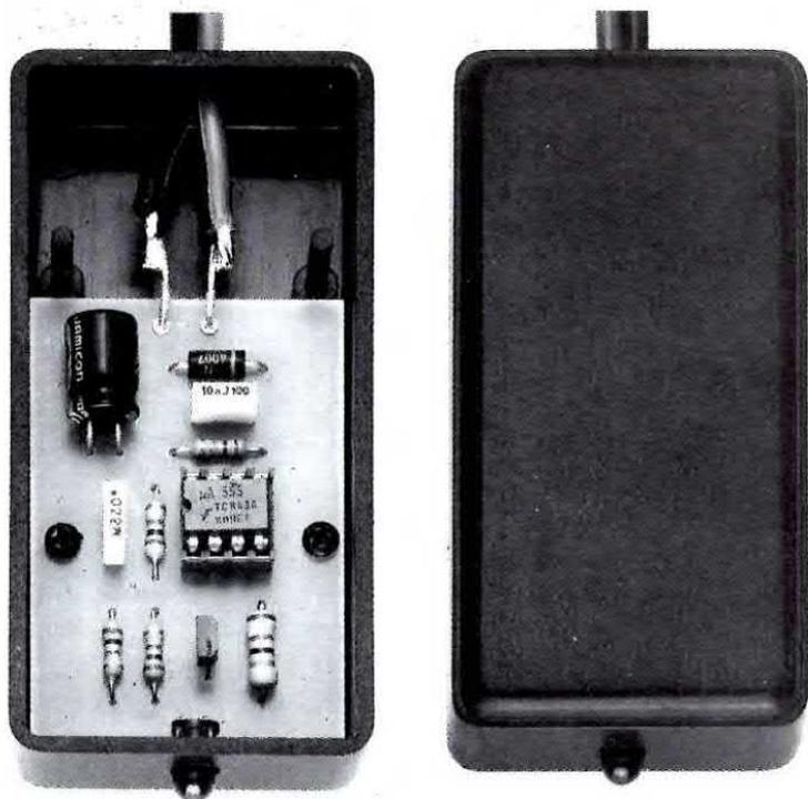
Fig.14 Lo stadio trasmittente LX.924 verrà racchiuso entro un piccolo contenitore plastico. Su tale contenitore dovrete praticare un foro per far uscire la testa del diodo trasmittente ed uno per il cavetto di alimentazione.
