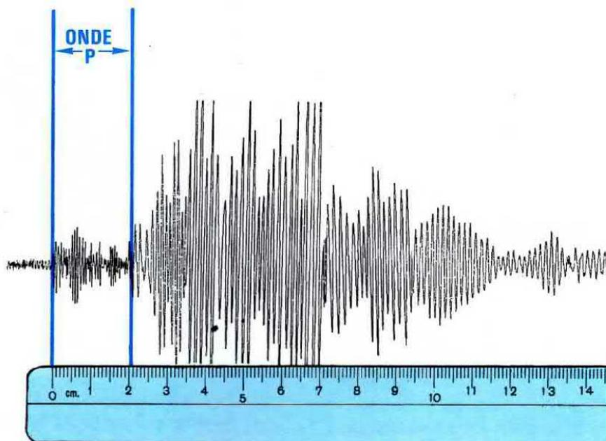
**Fig.31** Sempre se avremo predisposto la stampante per la velocità 1 (5 mm. x minuto) sapremo che un tracciato di "onda P" lungo 20 mm. corrisponde ad una distanza di 2.500 Km. Se la stampante l'avremo predisposta per la velocità 2 (10 mm. x minuto), dovremo servirci della seconda tabella a destra e in questo caso la distanza sarebbe di 1000 Km.
