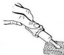
Fig.6 Eseguita una saldatura, dovrete togliere dalla punta del saldatore tutto lo stagno residuo, sfregandola sopra uno straccio o una spugna inumidita in acqua. Infatti questo stagno, risultando sprovvisto di disossidante, non potrà più assicurarvi una buona saldatura.
