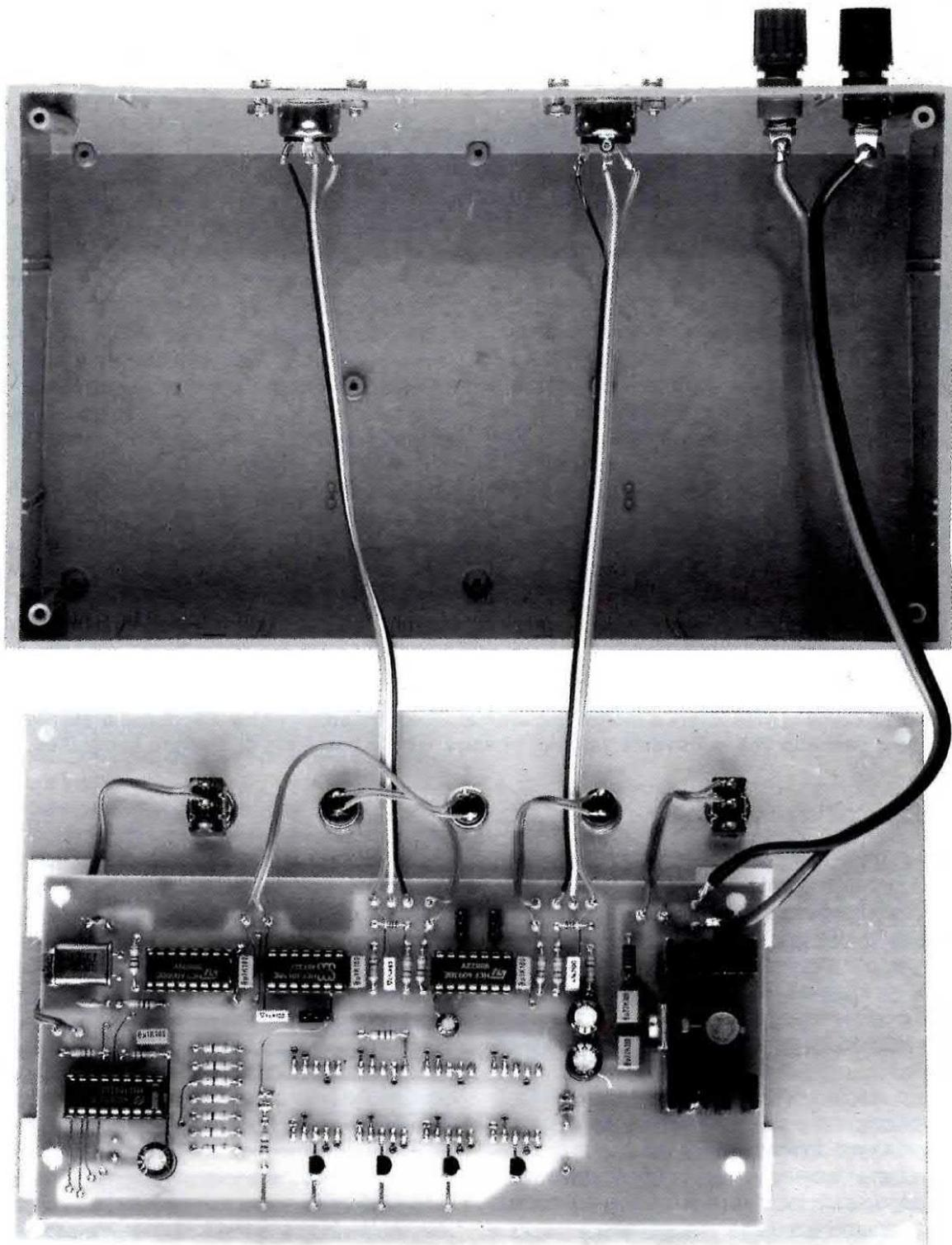
Fig.16 Il circuito stampato LX.926 verrà fissato sul pannello metallico del mobile con quattro distanziatori plastici autoadesivi. Sulla parte posteriore del mobile plastico fisserete le due bocche per la tensione di alimentazione e le due prese Din a 3 poli per collegare i due LX.925.
