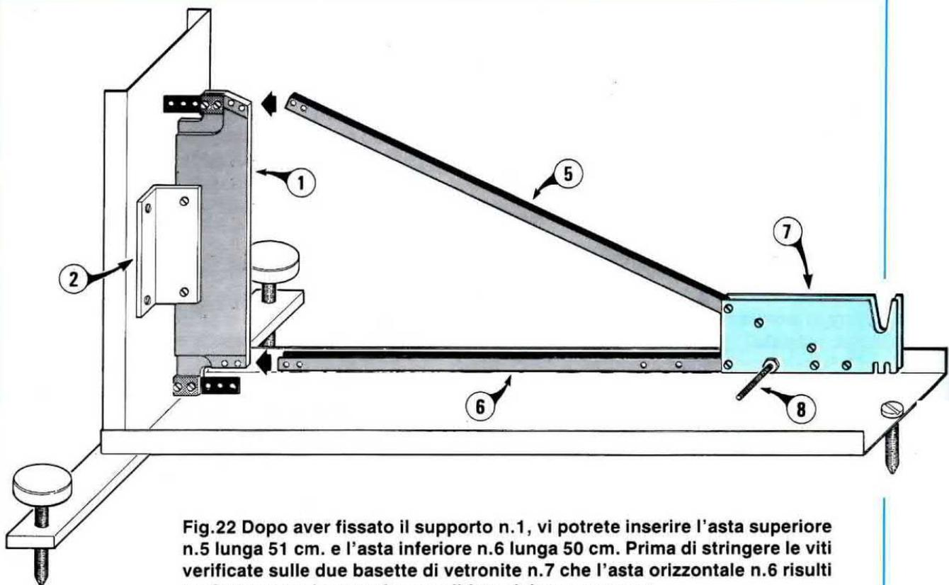
**Fig.22** Dopo aver fissato il supporto n.1, vi potrete inserire l'asta superiore n.5 lunga 51 cm. e l'asta inferiore n.6 lunga 50 cm. Prima di stringere le viti verificate sulle due basette di vetronite n.7 che l'asta orizzontale n.6 risulti perfettamente in squadra con il lato del supporto n.1.
