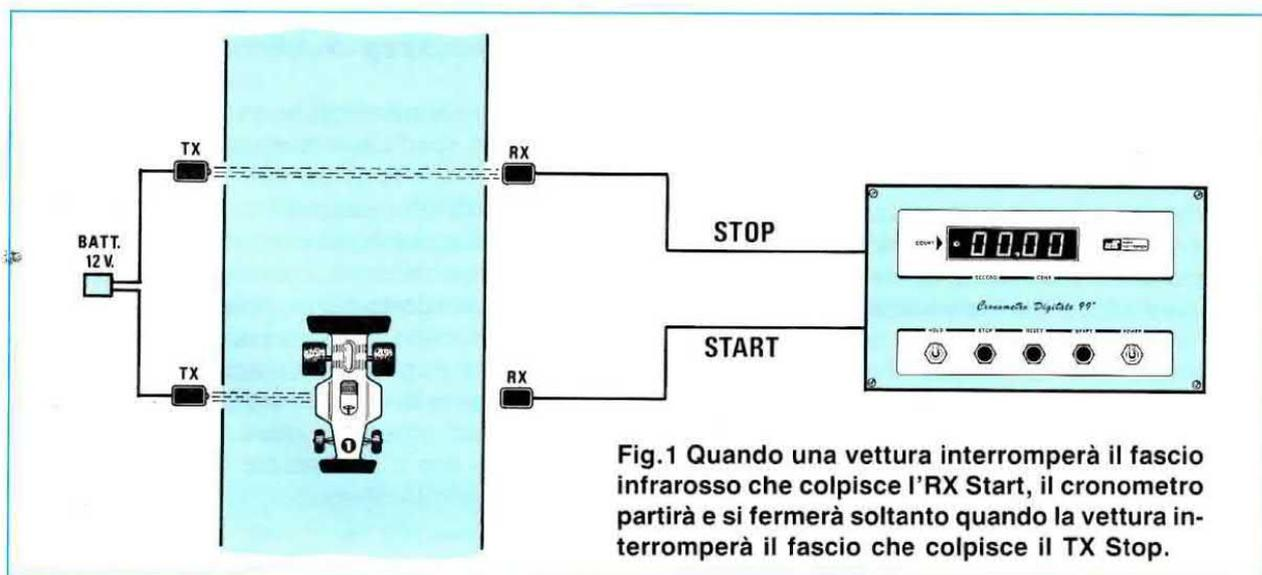
Se siete appassionati di automodellismo potrebbe esservi utile questo cronometro da pista, non solo per stabilire i tempi di ogni giro percorso in secondi e centesimi, ma anche per controllare se la vettura concorrente risulta più veloce della vostra.
