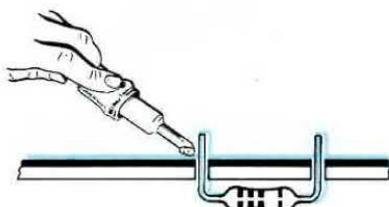
**Fig.3** Lo stagno fuso già presente sulla punta del saldatore sprovvisto di disossidante, si depositerà sulla pellicola di ossido che ricopre l'intera superficie del terminale e di conseguenza non consentirà alcun collegamento elettrico.
