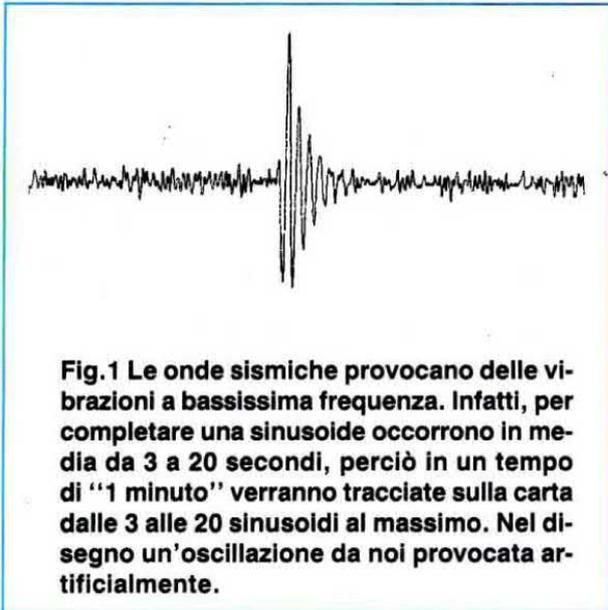
Pertanto un sismografo per registrare sia le **onde P** che le **onde S** ed **L**, dovrà essere in grado di oscillare sia con onde che abbiano un periodo di 20 secondi che di 3 secondi.
