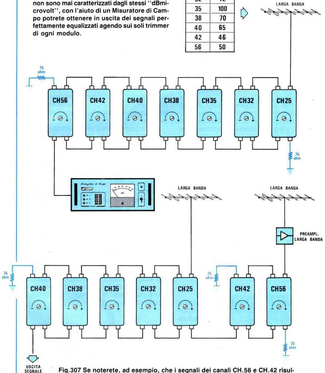
Fig.307 Se noterete, ad esempio, che i segnali dei canali CH.56 e CH.42 risultano notevolmente inferiori agli altri, dovrete necessariamente installare una seconda antenna e preamplificarli prima di inserirli negli ingressi dei due moduli CH.56 e CH.42. Il segnale captato dalla prima antenna entrerà nel modulo CH.25. Si noti la resistenza di chiusura sul modulo CH.42.
