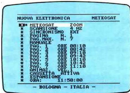
**Fig.13** Quando vorrete memorizzare su nastro una immagine, la prima operazione che dovrete compiere sarà quella di entrare nel Menù e selezionare il formato Meteosat o Polari Zoom.
