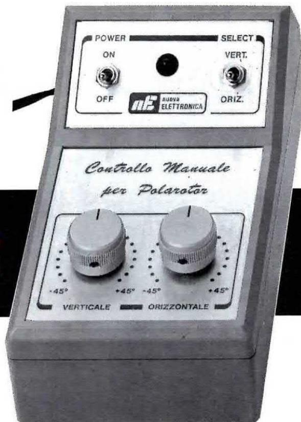
si ricevono meglio se si regola la polarizzazione non in senso orizzontale o verticale, ma sui 45° gradi circa, cioè in posizione inclinata.
