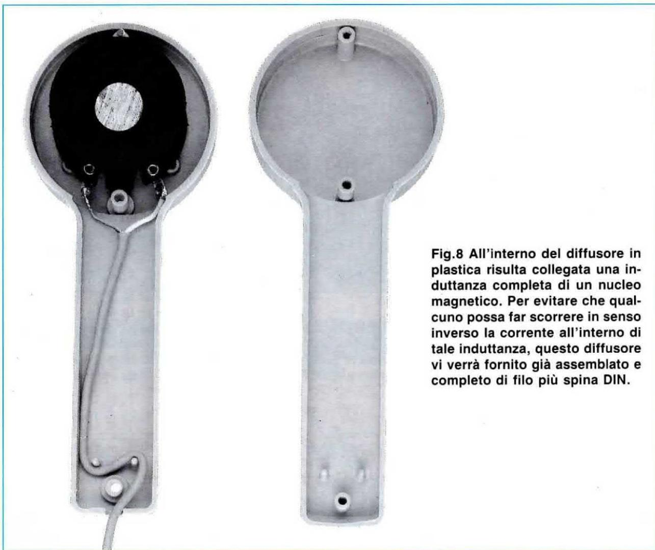
**Fig.8** All'interno del diffusore in plastica risulta collegata una induttanza completa di un nucleo magnetico. Per evitare che qualcuno possa far scorrere in senso inverso la corrente all'interno di tale induttanza, questo diffusore vi verrà fornito già assemblato e completo di filo più spina DIN.
