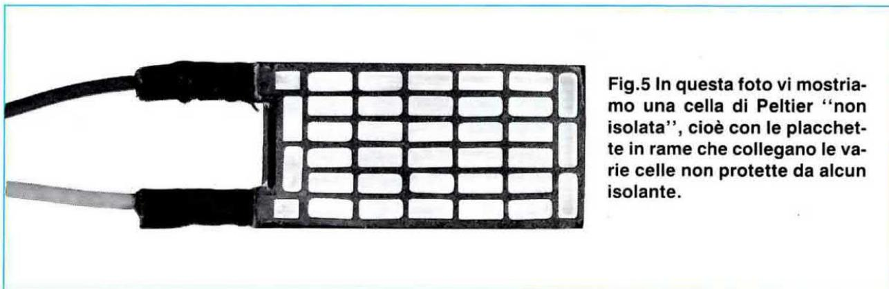
Fig.5 In questa foto vi mostriamo una cella di Peltier "non isolata", cioè con le placchette in rame che collegano le varie celle non protette da alcun isolante.
