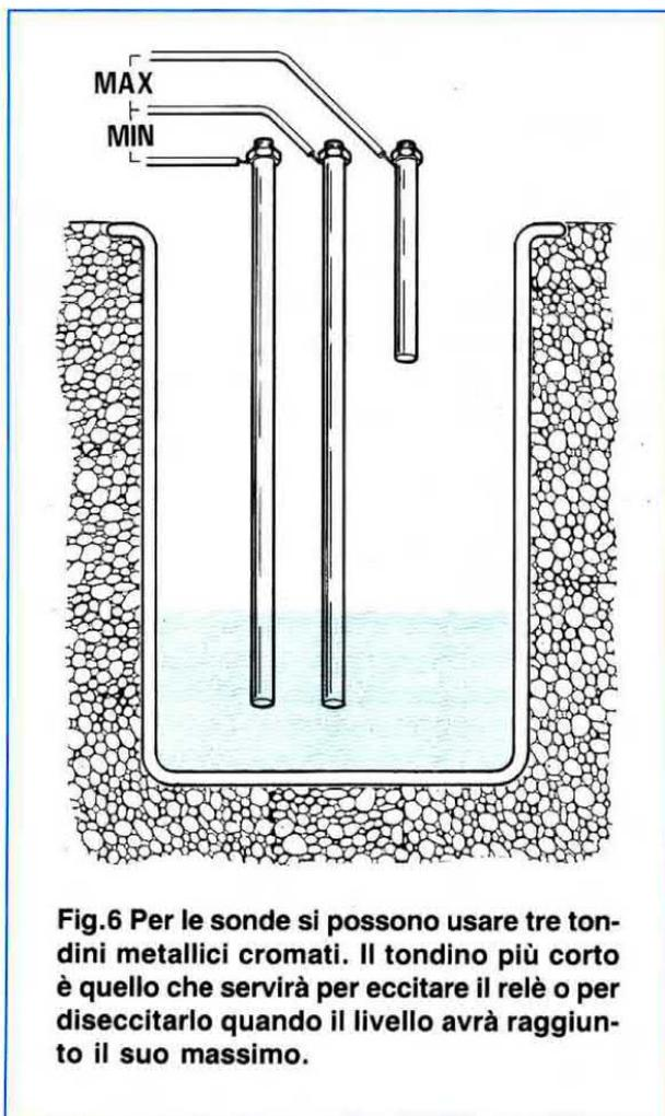
**Fig.6** Per le sonde si possono usare tre tondini metallici cromati. Il tondino più corto è quello che servirà per eccitare il relè o per diseccitarlo quando il livello avrà raggiunto il suo massimo.
