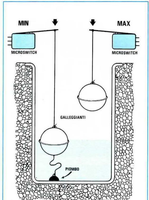
**Fig.8** Alle due leve andranno collegati dei galleggianti con un filo di nailon. Sui due microswitch andranno utilizzati i due terminali che risultano "aperti" quando il livello del liquido è sotto al minimo e "chiusi" quando il livello ha raggiunto il suo massimo.
