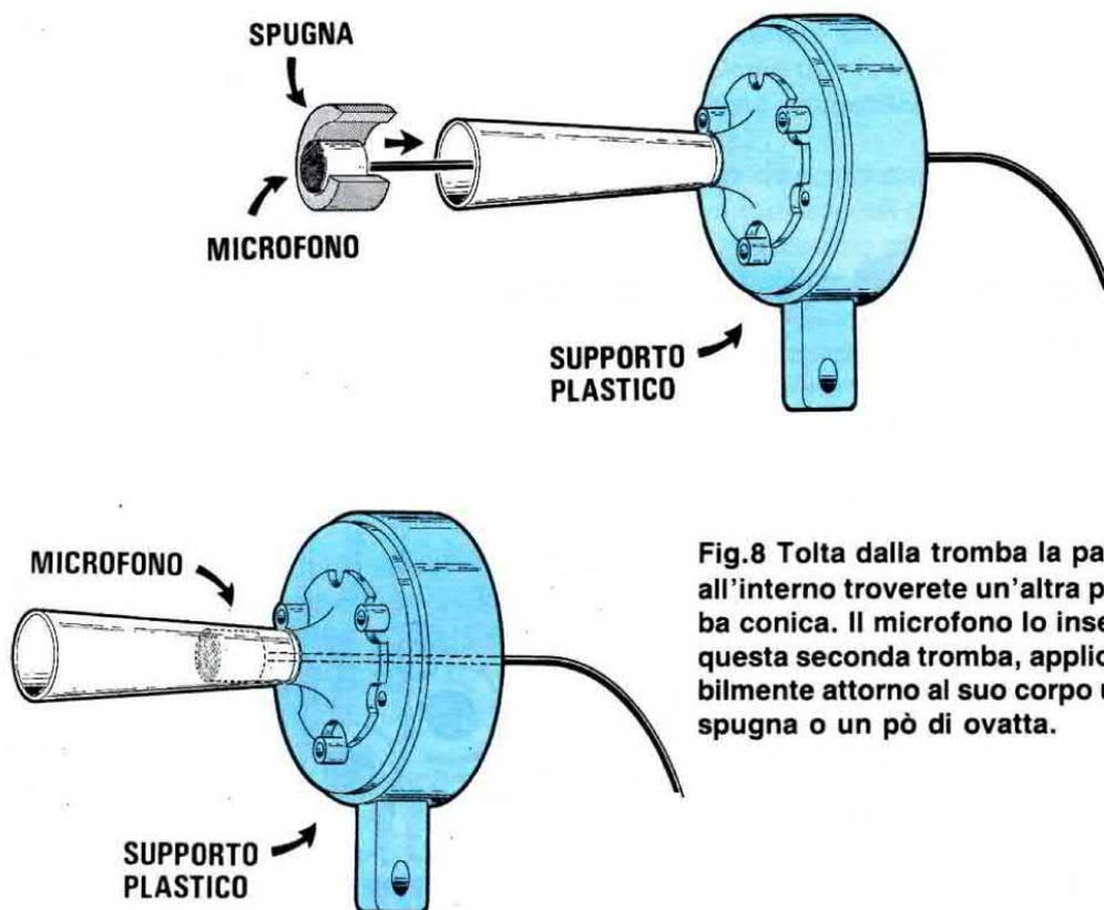
Fig.8 Tolta dalla tromba la parte frontale, all'interno troverete un'altra piccola tromba conica. Il microfono lo inserirete entro questa seconda tromba, applicando possibilmente attorno al suo corpo un ritaglio di spugna o un pò di ovatta.
