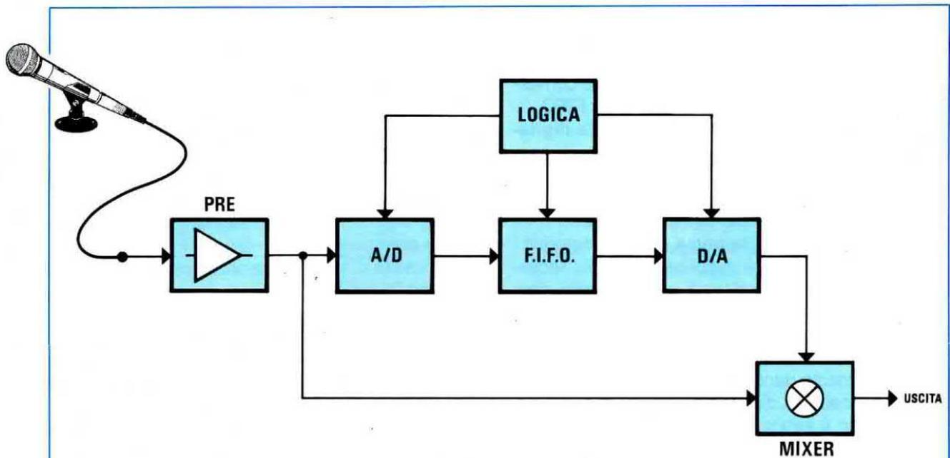
**Fig.5** Un eco elettronico potrebbe essere così schematizzato. Il segnale captato dal microfono viene inviato contemporaneamente sul miscelatore d'uscita e sull'ingresso di un convertitore Analogico/Digitale per poterlo poi memorizzare nella FIFO. Il segnale prelevato dalla FIFO verrà ricoverito da Digitale ad Analogico, quindi miscelato con il segnale diretto. Un circuito logico provvederà a commutare sia il segnale di scrittura che quello di lettura come illustrato nelle figg.1-2-3.
