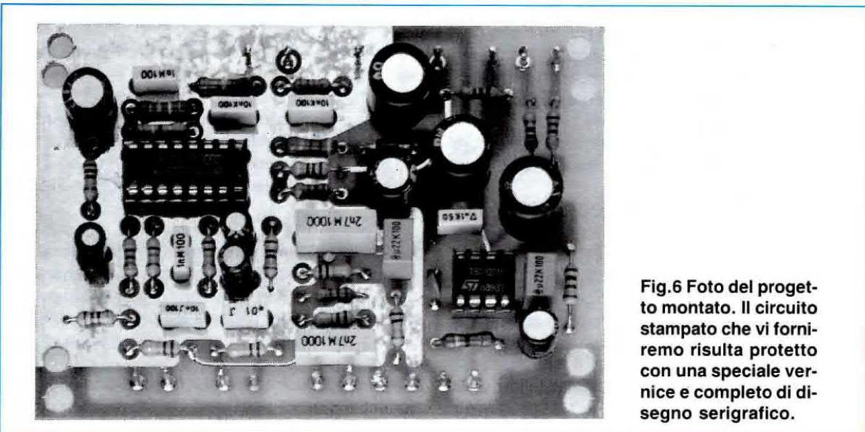
Fig.6 Foto del progetto montato. Il circuito stampato che vi forniremo risulta protetto con una speciale vernice e completo di disegno serigrafico.
