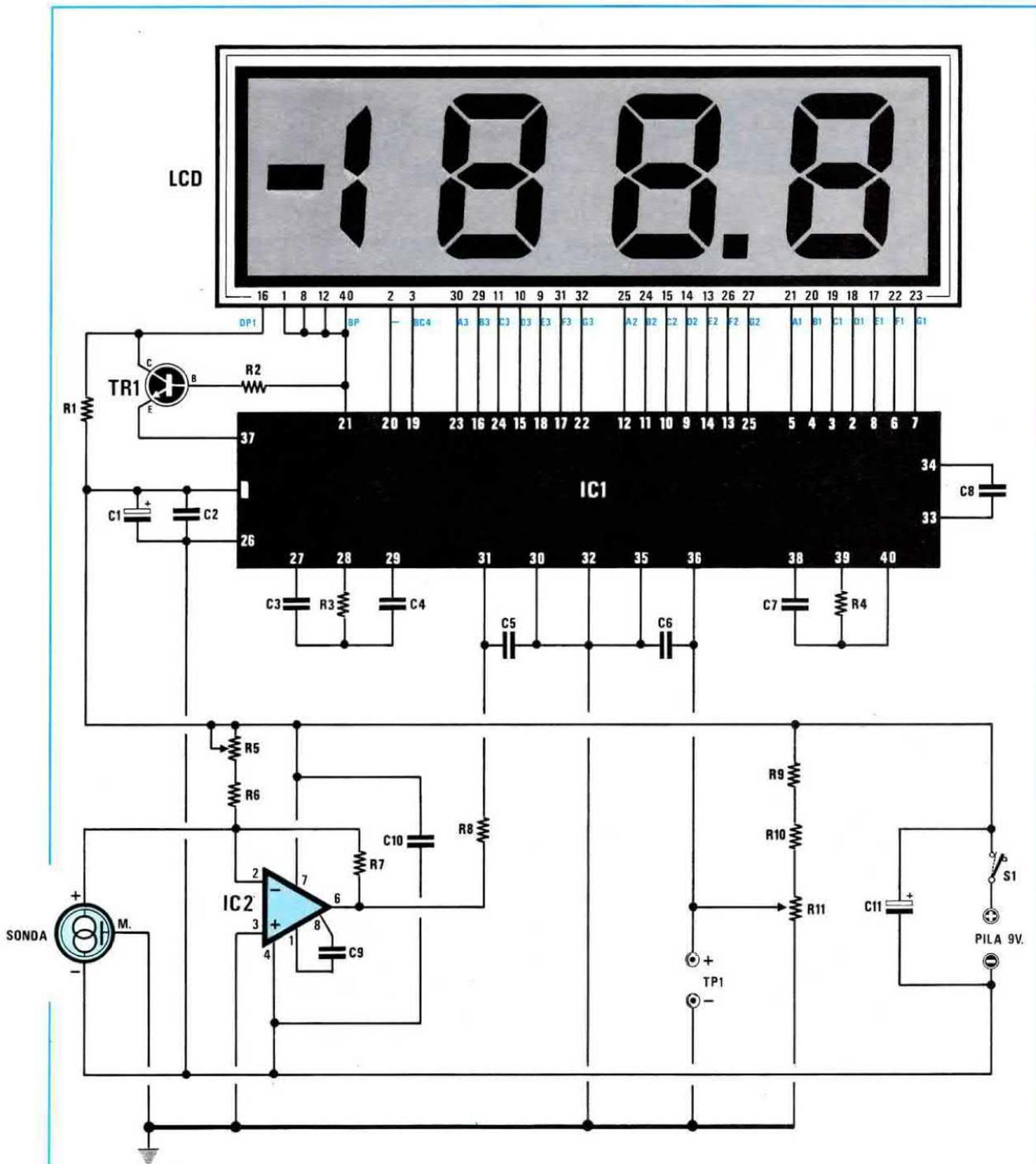
Fig.2 Schema elettrico del termometro e connessioni della sonda AD.590 e del transistor BC.237 viste da sotto. Le connessioni dell'integrato CA.3130 sono invece viste da sopra.
