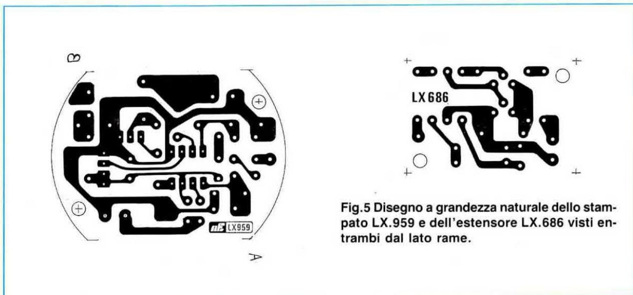
Fig.5 Disegno a grandezza naturale dello stampato LX.959 e dell'estensore LX.686 visti entrambi dal lato rame.
