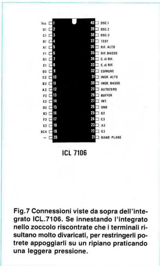
Fig.7 Connessioni viste da sopra dell'integrato ICL.7106. Se innestando l'integrato nello zoccolo riscontrate che i terminali risultano molto divaricati, per restringerli potreste appoggiarli su un ripiano praticando una leggera pressione.
