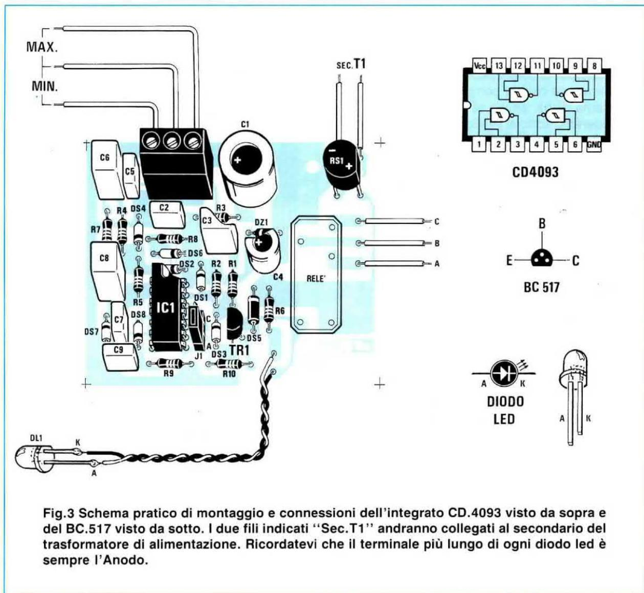
Fig.3 Schema pratico di montaggio e connessioni dell'integrato CD.4093 visto da sopra e del BC.517 visto da sotto. I due fili indicati "Sec.T1" andranno collegati al secondario del trasformatore di alimentazione. Ricordatevi che il terminale più lungo di ogni diodo led è sempre l'Anodo.
