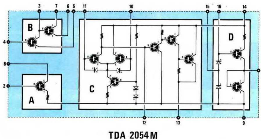
**Fig.1** All'interno dell'integrato **TDA.2054** sono presenti 11 transistor. Lo stadio A lo sfruttiamo per preamplificare il segnale captato dal microfono. Lo stadio B lo utilizziamo come stadio separatore per i filtri passa-alto e passa-basso. Lo stadio C, composto da 6 transistor, servirà per amplificare il segnale prelevato dallo stadio A. Mentre l'ultimo stadio D, lo utilizziamo per realizzare il Controllo Automatico di Livello (vedi schema elettrico in fig.4).
