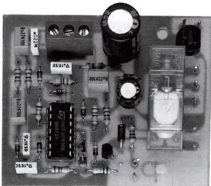
Fig.1 In questa foto è ben evidente la semplicità di questo circuito utile per riempire o svuotare automaticamente una qualsiasi cisterna.
