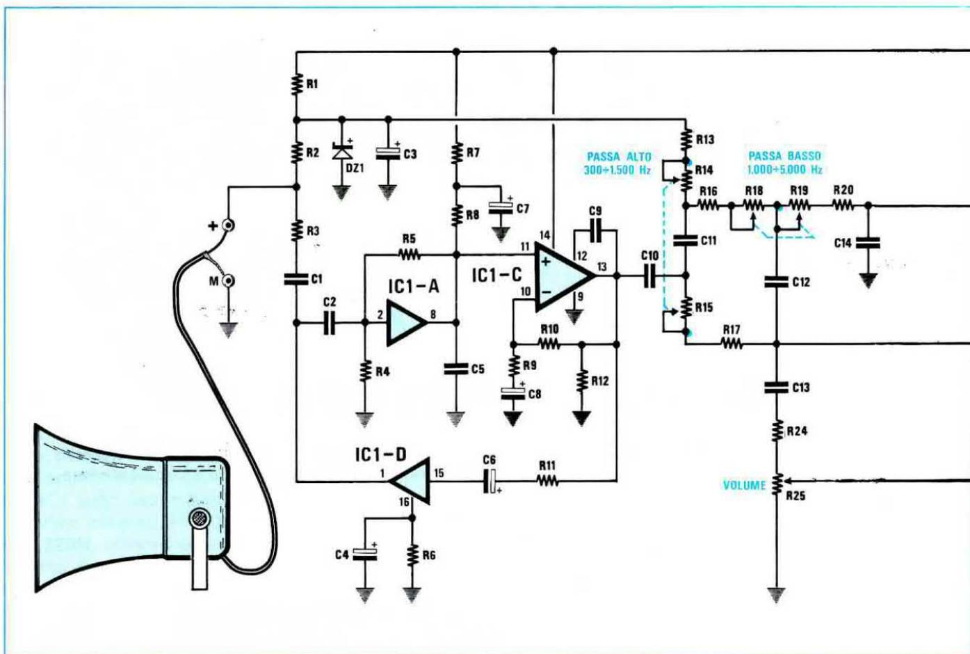
Fig.4 Schema elettrico del microfono per l'ascolto a distanza. Per rendere lo schema più leggibile abbiamo tenuto separati gli stadi presenti all'interno dell'integrato TDA.2054 (vedi IC1/A - IC1/B - IC1/C - IC1/D).
