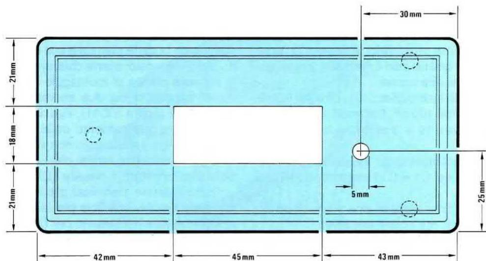
**Fig.8** Poichè il coperchio del mobile non risulta forato, vi riportiamo un disegno con tutte le quote richieste. Per ricavare l'asola centrale di forma rettangolare senza praticare tanti fori su tutto il perimetro interno, potrete fondere con un saldatore la parte centrale dell'asola e rifinirne i bordi con una lima.
