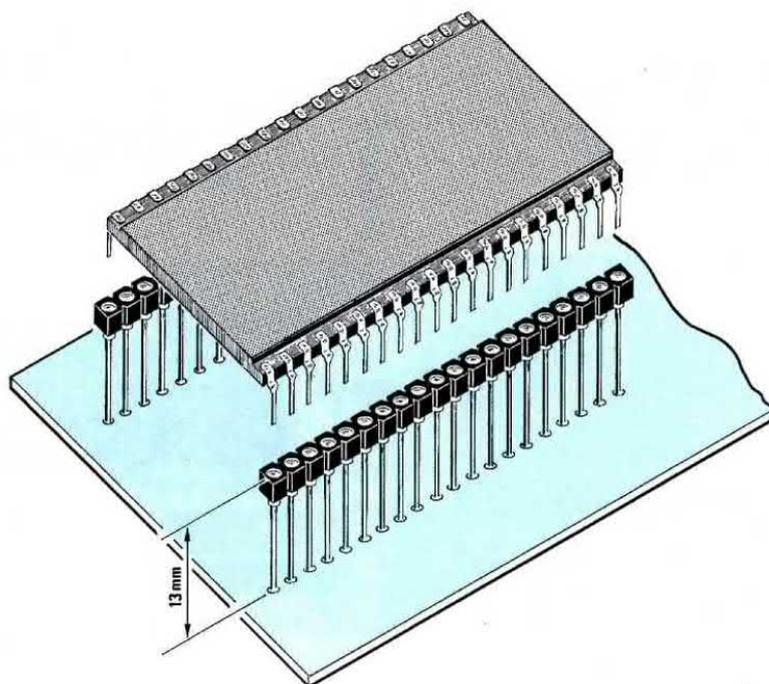
**Fig.5** Le due file di connettori femmina che utilizzeremo come zoccolo per il display LCD, andranno fissate sullo stampato tenendole distanziate dalla base di 13 millimetri. Prima di saldare tutti i terminali, verificate che i due connettori risultino perfettamente orizzontali.
