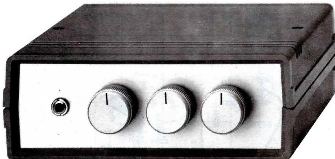
**Fig.2** Sul pannello frontale del mobile dovreste fissare i tre potenziometri e la presa "ingresso microfono". La presa "cuffia" andrà necessariamente applicata sul pannello posteriore, perchè il dado di fissaggio risulta collegato al "positivo" della pila.
