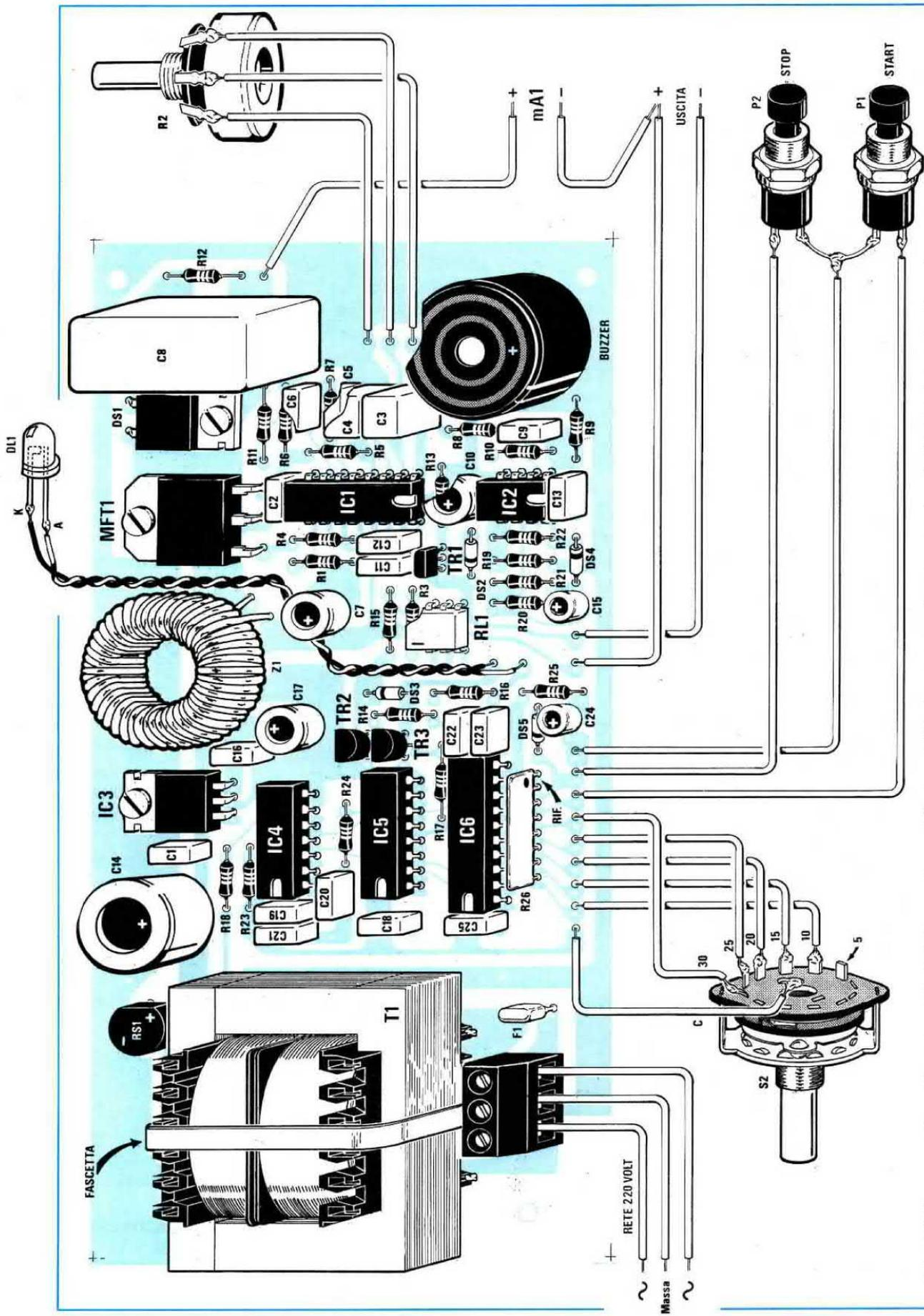
Fig.8 Schema pratico di montaggio del Generatore. A destra, i fili che vanno allo strumento ed alle due bocche di uscita.
