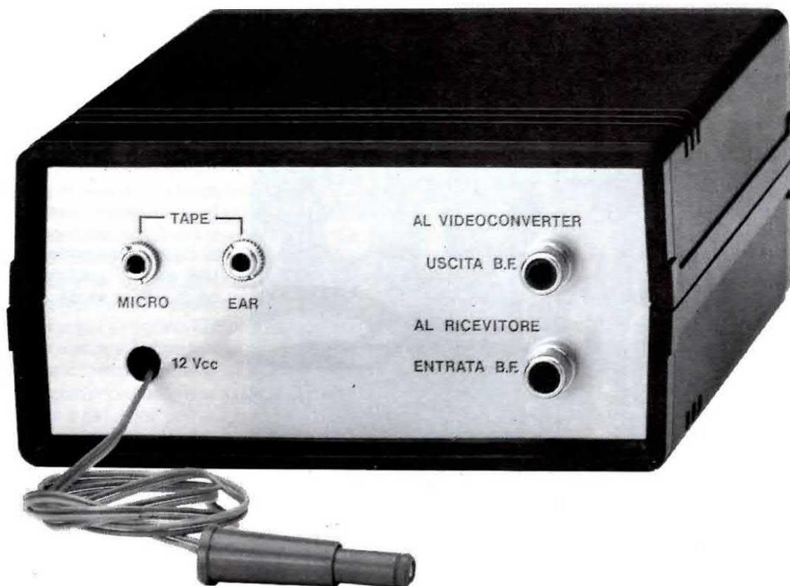
**Fig.19** Sul pannello posteriore del mobile fisserete la presa femmina per l'ingresso del segnale di BF (da collegare al ricevitore) e quella di uscita (da collegare al Videoconverter). Per il registratore utilizzerete le due prese jack visibili a sinistra. La presa "Micro" serve per farlo entrare nel registratore, la presa "Ear" per prelevarlo.
