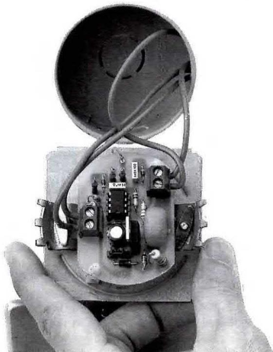
**Fig.11** Il circuito già pronto per essere racchiuso entro la scatola in plastica murata nella parete. I due fili di destra vanno innestati nell'interruttore meccanico, mentre i due fili di sinistra per il collegamento al sensore visibile in fig.14. Facciamo presente che se non si rispettano la Fase ed il Neutro dei due fili di rete a 220 volt, il circuito non potrà funzionare.
