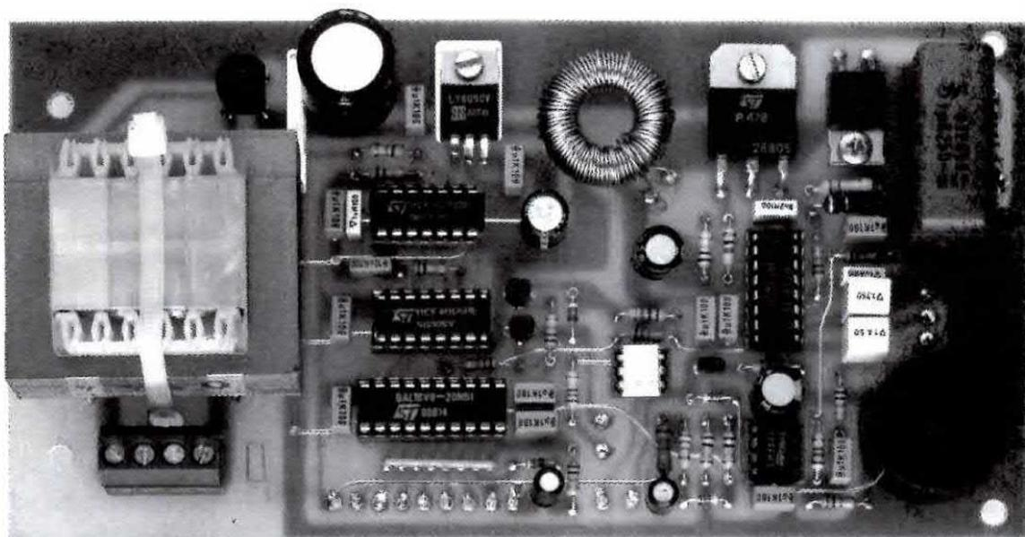
**Fig.9** Foto del circuito come si presenta a montaggio ultimato. Per evitare in caso di caduta del mobile o durante il trasporto, che i terminali del trasformatore di alimentazione si spezzino, andrà fissato sullo stampato con la fascetta di plastica inclusa nel kit.
