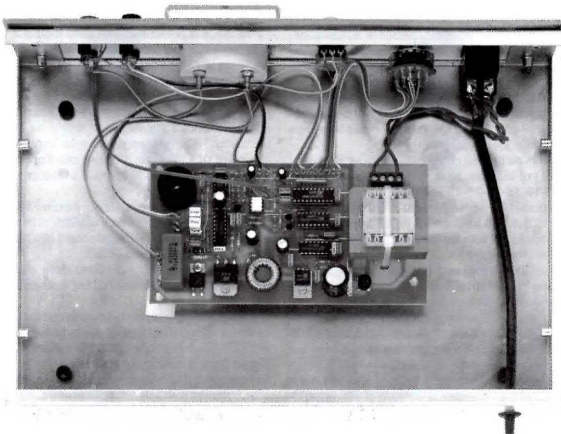
**Fig.10** Lo stampato andrà fissato all'interno del mobile con quattro distanziatori plastici con base autoadesiva. Per i collegamenti elettrici con il commutatore rotativo, le bocche d'uscita, lo strumento e pulsanti e il potenziometro vedere la fig.8.
