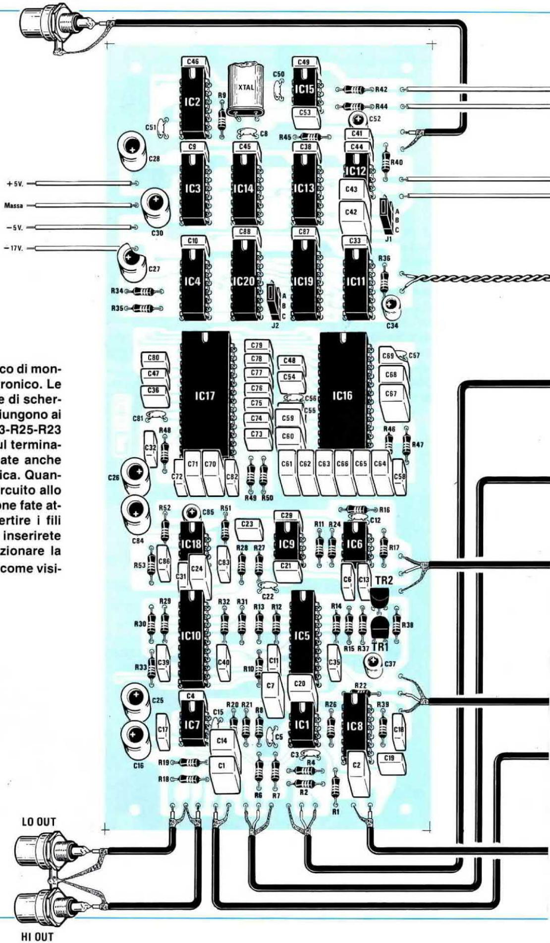
Fig.13 Schema pratico di montaggio dell'Eco elettronico. Le estremità delle calze di schermo dei cavetti che giungono ai potenziometri R5-R3-R25-R23 andranno saldate sul terminale estremo e collegate anche alla carcassa metallica. Quando collegherete il circuito allo stadio di alimentazione fate attenzione a non invertire i fili +/- 5 volt e quando inserirete gli integrati, a posizionare la tacca di riferimento come visibile in figura.
