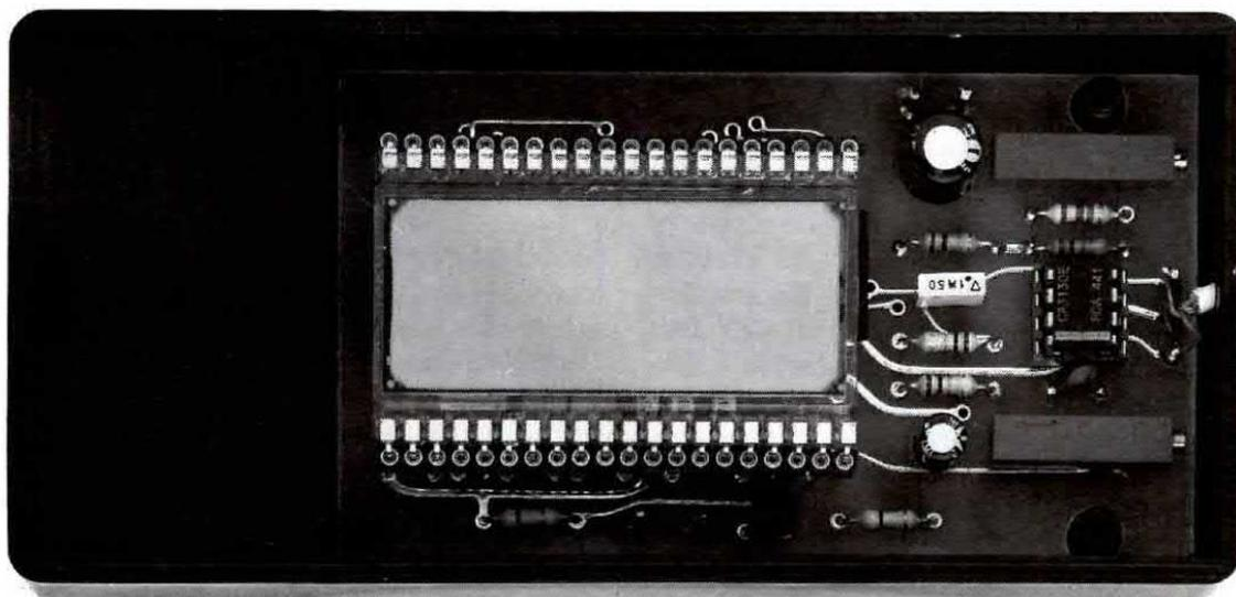
**Fig.9** Il circuito stampato verrà fissato sul mobile con due viti autofilettanti (vedi lato sinistro). Prima di fissare il circuito, non dimenticate di aprire sul lato destro un foro per far fuoriuscire il cavetto da collegare alla sonda e due fori in corrispondenza dei trimmer R5-R11 per poterli tarare dall'esterno con un sottile cacciavite.
