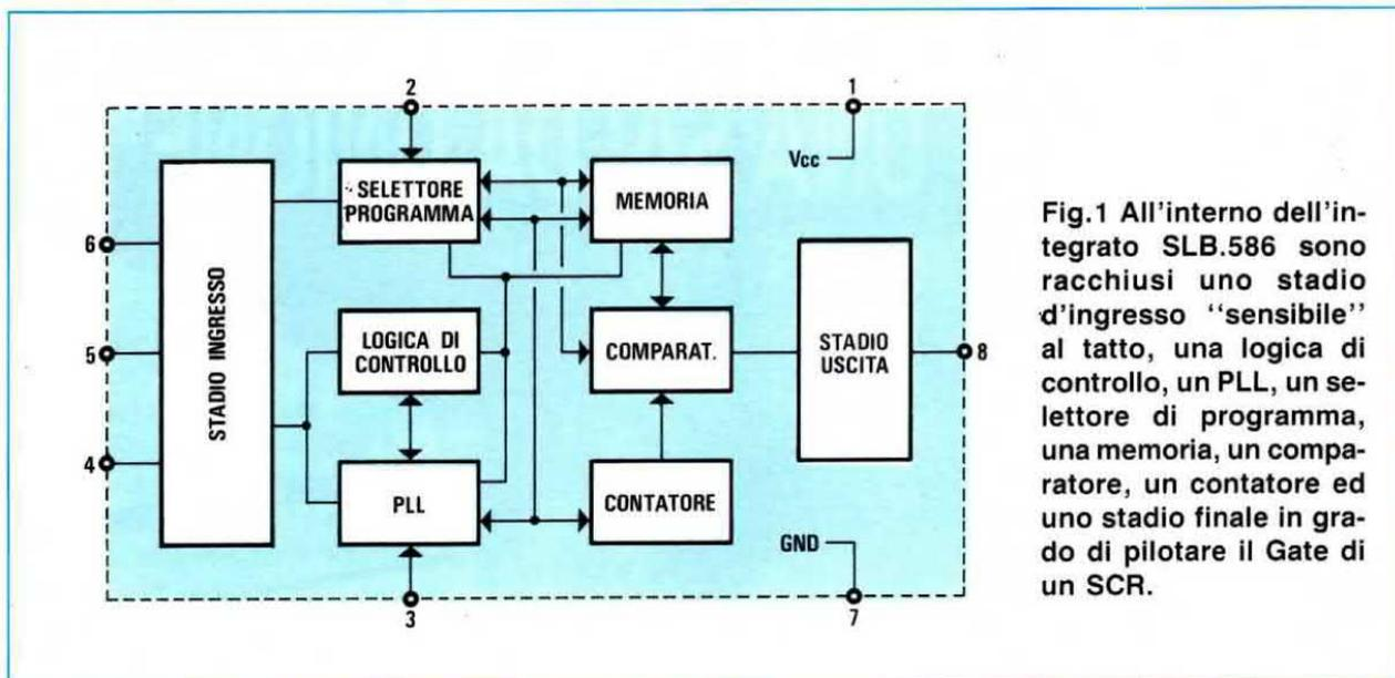
Fig.1 All'interno dell'integrato SLB.586 sono racchiusi uno stadio d'ingresso "sensibile" al tatto, una logica di controllo, un PLL, un selettore di programma, una memoria, un comparatore, un contatore ed uno stadio finale in grado di pilotare il Gate di un SCR.
