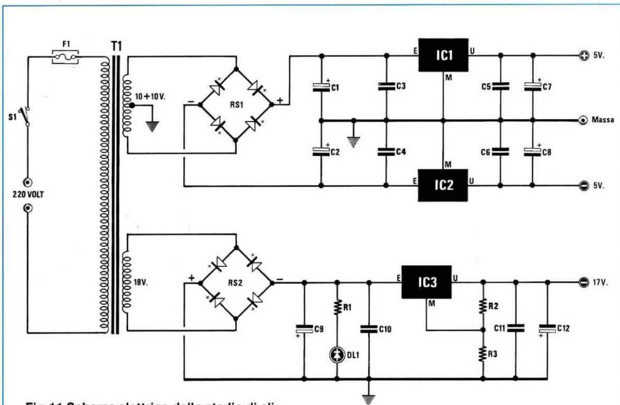
Fig.11 Schema elettrico dello stadio di alimentazione. Si noti il collegamento di IC3 necessario per ottenere con un uA.7915 una tensione stabilizzata di -17 volt.
