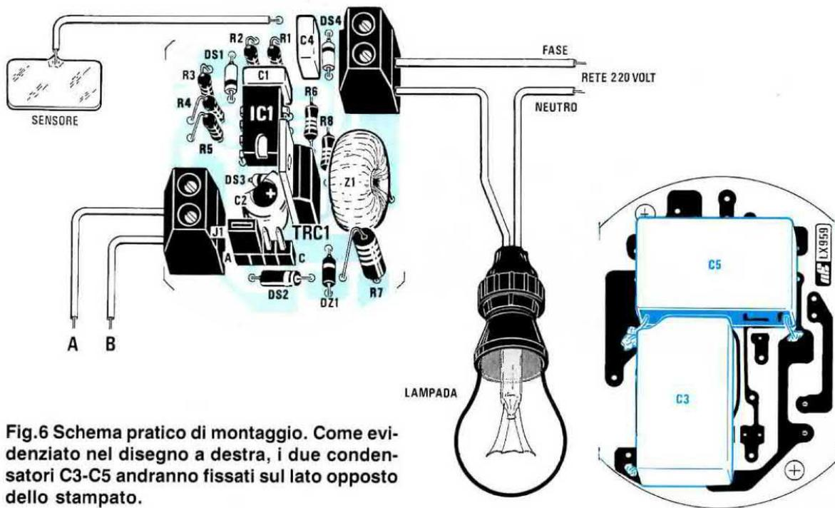
Fig. 6 Schema pratico di montaggio. Come evidenziato nel disegno a destra, i due condensatori C3-C5 andranno fissati sul lato opposto dello stampato.
