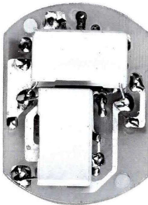
Fig. 8 I due condensatori C3-C5 da 100.000 pF 630 Volt lavoro, andranno applicati sul retro dello stampato e i loro terminali, direttamente saldati sulle piste in rame.
