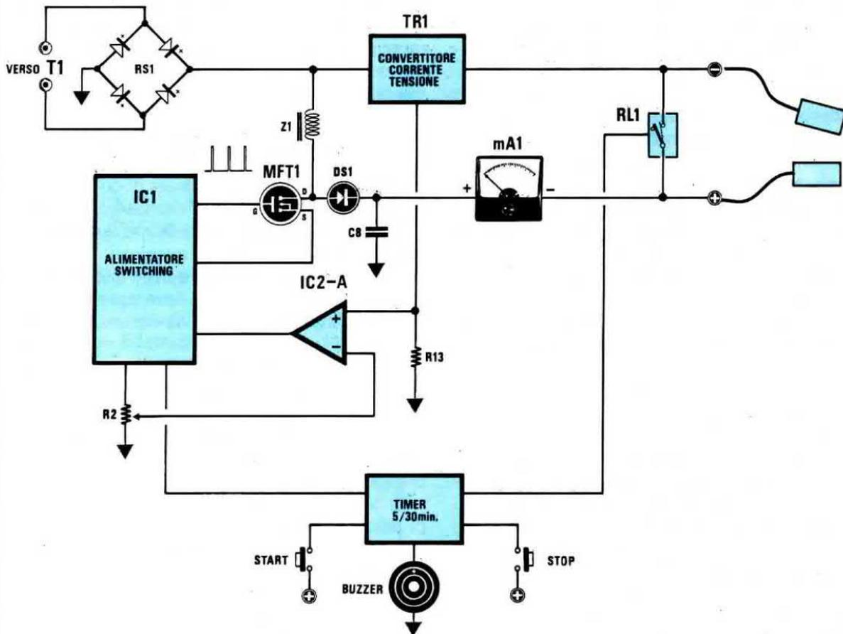
Fig.4 Schema a blocchi del nostro Generatore di corrente costante progettato per la lonoforesi. Come si può notare, la tensione da applicare agli elettrodi non la preleviamo direttamente dal secondario di un trasformatore, bensì da un alimentatore switching per poterne automaticamente controllare la corrente in uscita. Il circuito è completo di un timer che, trascorso il tempo prefissato, interromperà la corrente.
