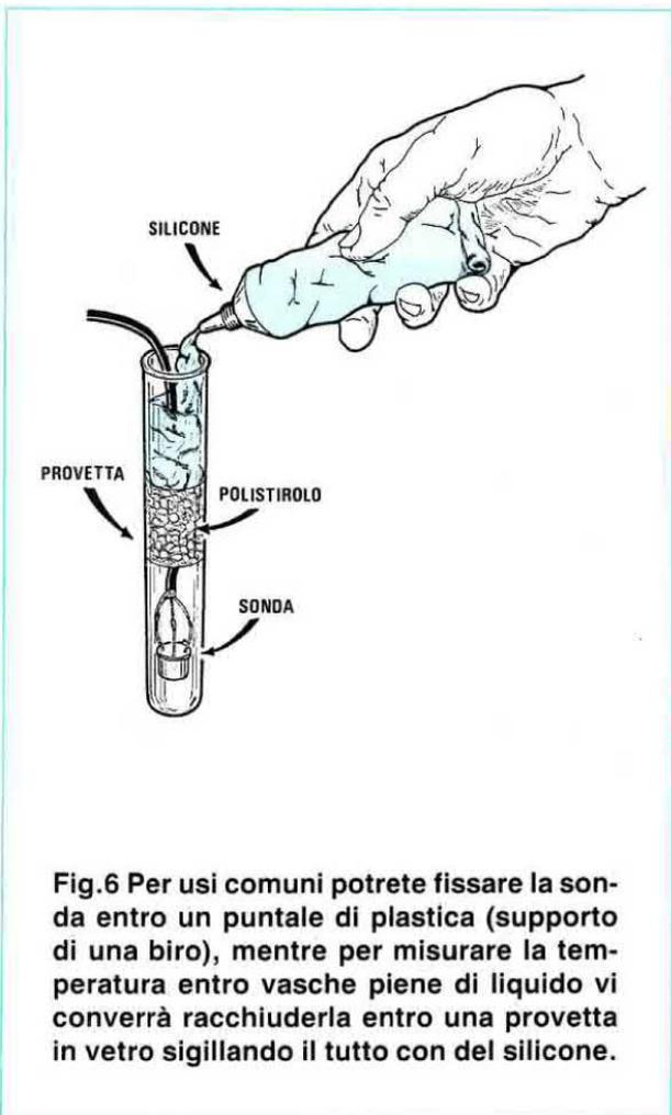
Fig.6 Per usi comuni potreste fissare la sonda entro un puntale di plastica (supporto di una biro), mentre per misurare la temperatura entro vasche piene di liquido vi converrà racchiuderla entro una provetta in vetro sigillando il tutto con del silicone.
