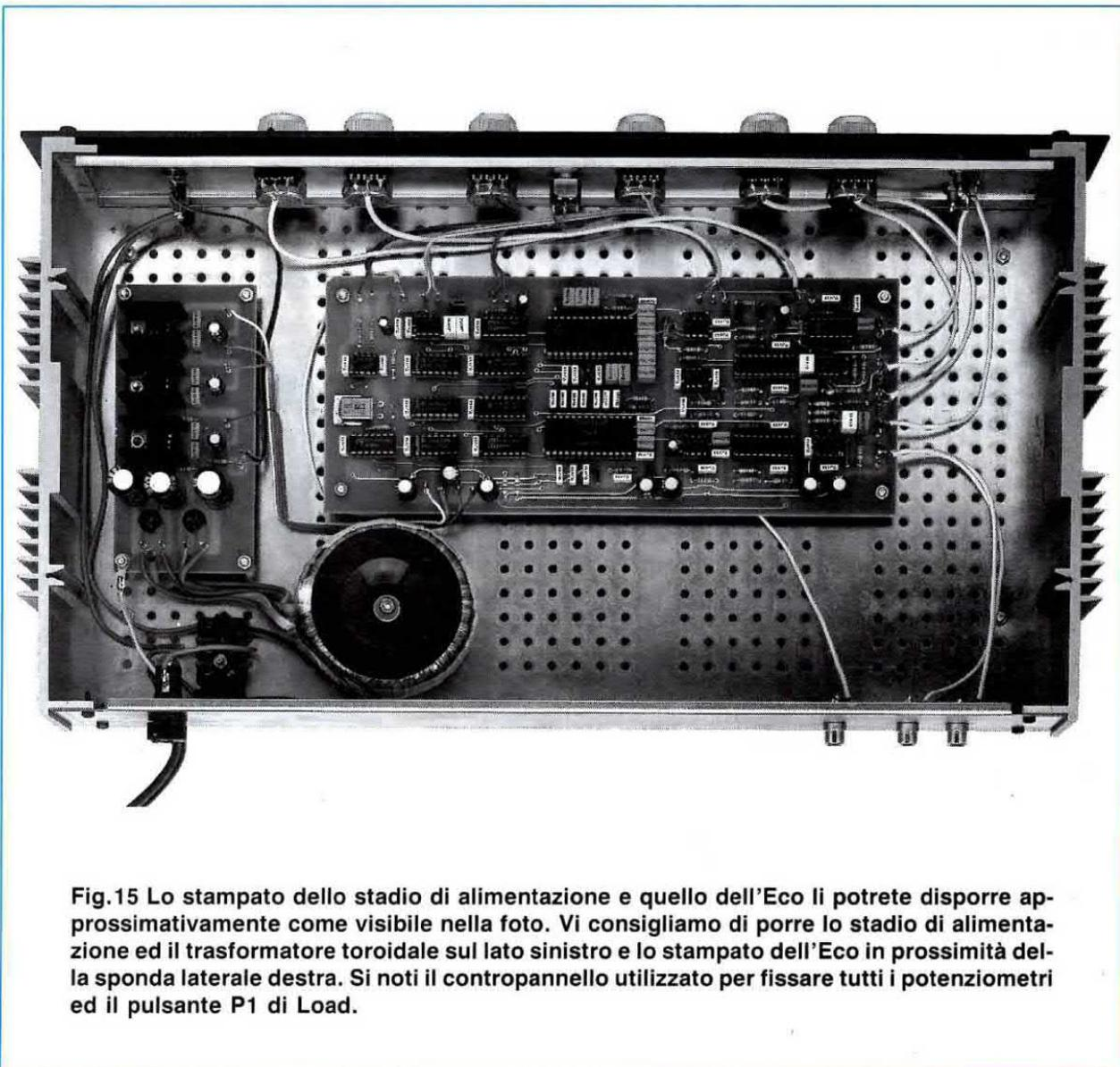
**Fig.15** Lo stampato dello stadio di alimentazione e quello dell'Eco li potrete disporre approssimativamente come visibile nella foto. Vi consigliamo di porre lo stadio di alimentazione ed il trasformatore toroidale sul lato sinistro e lo stampato dell'Eco in prossimità della sponda laterale destra. Si noti il contropannello utilizzato per fissare tutti i potenziometri ed il pulsante P1 di Load.
