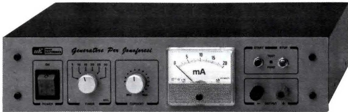
Nella foto possiamo vedere come si presenta il mobile da noi prescelto per questo generatore di ionoforesi. Sulla sinistra l'interruttore basculante illuminato e sulla destra i due morsetti d'uscita per le due placche conduttrici.
