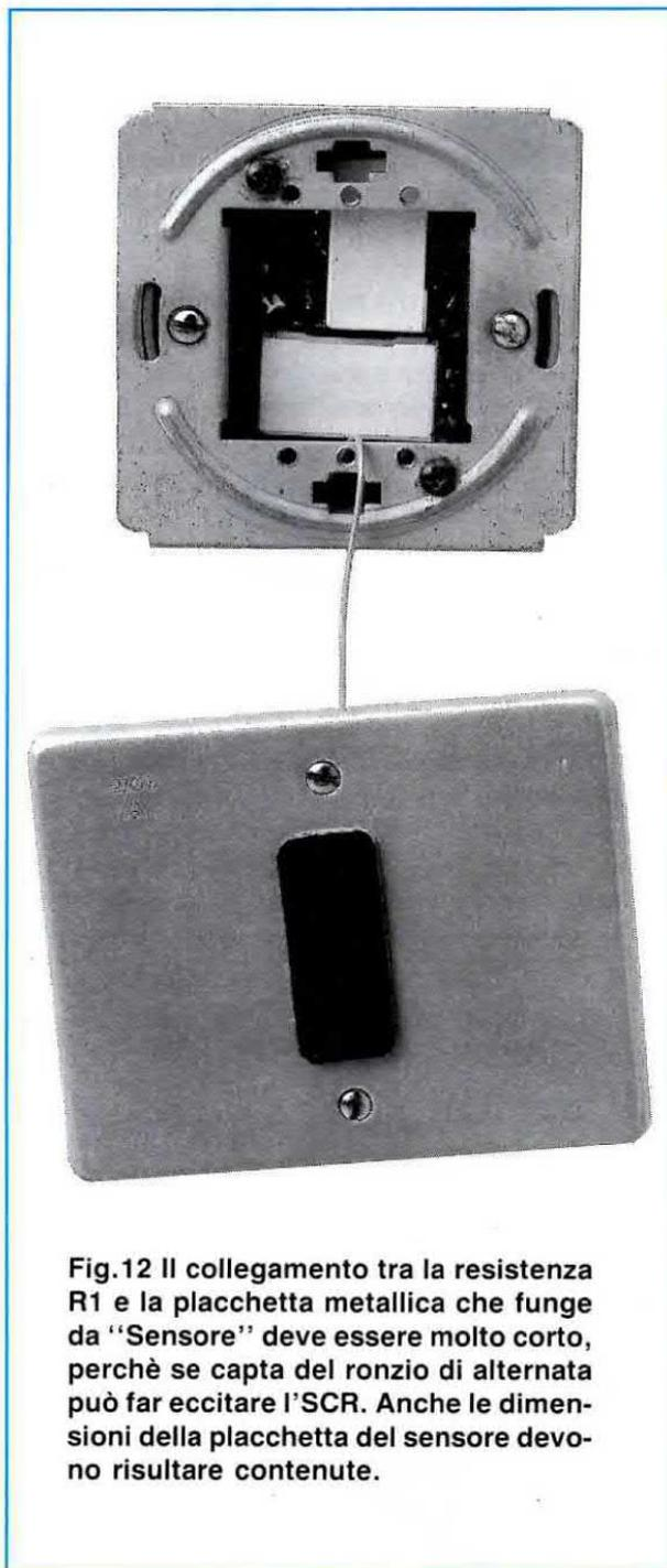
**Fig.12 Il collegamento tra la resistenza R1 e la placchetta metallica che funge da "Sensore" deve essere molto corto, perchè se capta del ronzio di alternata può far eccitare l'SCR. Anche le dimensioni della placchetta del sensore devono risultare contenute.**
