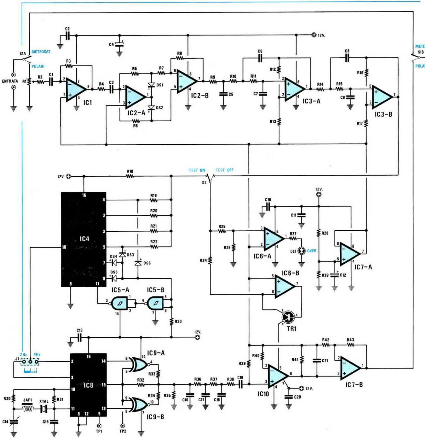
Fig.7 Schema elettrico del sincronizzatore per satelliti polari Russi. Il sincronizzatore va collegato tra l'uscita del ricevitore ed il Videoconverter. Alle uscite (vedi in alto a destra) potrete collegare contemporaneamente anche un registratore a nastro. La funzione Test serve per vedere sullo schermo delle barre a colori (vedi fig.13).
