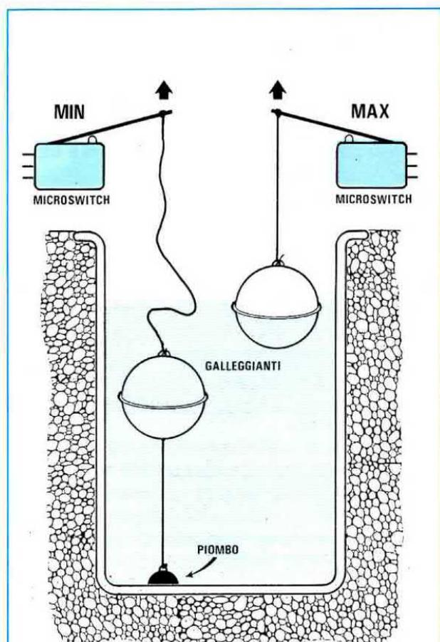
**Fig.9** È consigliabile applicare sul solo galleggiante del Minimo un piombo per evitare che a cisterna piena questo possa salire in superficie ed involontariamente attorcigliarsi sul filo dell'altro galleggiante quando il liquido della cisterna scende.
