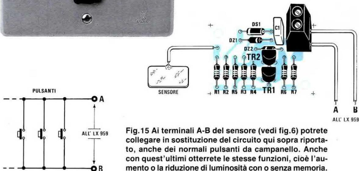
Fig.15 Ai terminali A-B del sensore (vedi fig.6) potrete collegare in sostituzione del circuito qui sopra riportato, anche dei normali pulsanti da campanello. Anche con quest'ultimi otterrete le stesse funzioni, cioè l'aumento o la riduzione di luminosità con o senza memoria.
