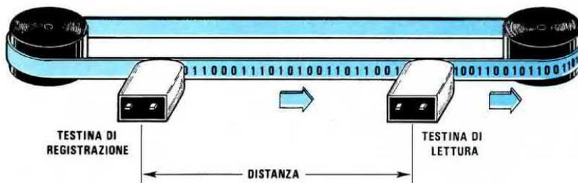
**Fig.4** Se in sostituzione di una FIFO utilizzassimo un registratore a nastro, potremmo ottenere ugualmente questo ritardo allontanando le due testine una dall'altra. Per apprezzare che il segnale di lettura risulta in ritardo rispetto a quello di scrittura, è indispensabile che il segnale applicato alla testina di registrazione venga miscelato ed amplificato assieme al segnale che preleveremo dalla testina di lettura.
