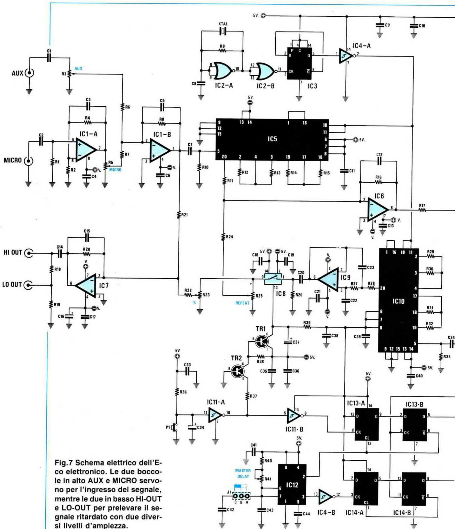
Fig.7 Schema elettrico dell'E-co elettronico. Le due bocche in alto AUX e MICRO servono per l'ingresso del segnale, mentre le due in basso HI-OUT e LO-OUT per prelevare il segnale ritardato con due diversi livelli d'ampiezza.
