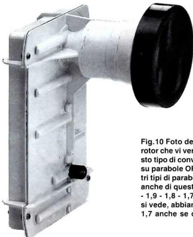
**Fig.10** Foto del convertitore LNC completo di Polartor che vi verrà fornito assieme alla parabola. Questo tipo di convertitore può essere installato soltanto su parabole OFFSET, quindi non utilizzatelo con altri tipi di parabole. Come per tutti i convertitori LNC, anche di questi ne troviamo con una NF da 2,2 - 2,0 - 1,9 - 1,8 - 1,7 dB, e poichè minore è la NF meglio si vede, abbiamo richiesto il modello con una NF = 1,7 anche se di costo superiore.
