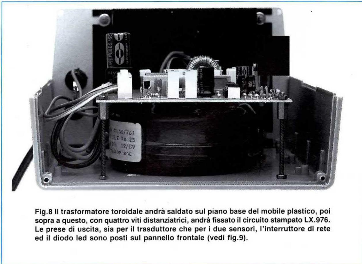
Fig.8 Il trasformatore toroidale andrà saldato sul piano base del mobile plastico, poi sopra a questo, con quattro viti distanziatrici, andrà fissato il circuito stampato LX.976. Le prese di uscita, sia per il trasduttore che per i due sensori, l'interruttore di rete ed il diodo led sono posti sul pannello frontale (vedi fig.9).
