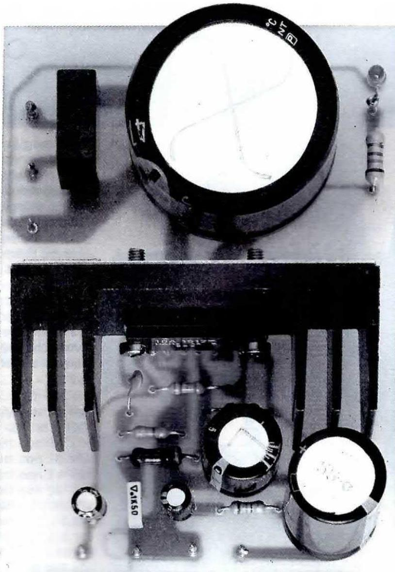
Fig.5 Di lato, una foto notevolmente ingrandita di uno dei nostri esemplari montati per il collaudo. Si notino il ponte raddrizzatore rettangolare ed il grosso condensatore elettrolitico C8 posto sullo stadio di alimentazione.
