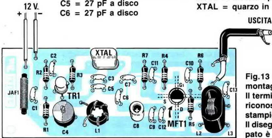
Fig.13 Schema pratico di montaggio dell'LX.1018/C. Il terminale D del mosfet si riconosce dalla mezzaluna stampigliata sul suo corpo. Il disegno del circuito stampato è visibile in fig.21.
