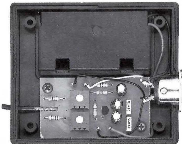
**Fig.1** In questa foto, il circuito stampato già fissato entro la scatola in plastica. Lo spazio superiore serve per la pila da 9 volt. Da un lato della scatola uscirà il cavetto della sonda NTC, mentre sul lato opposto andrà applicato il connettore d'uscita per il Tester.
