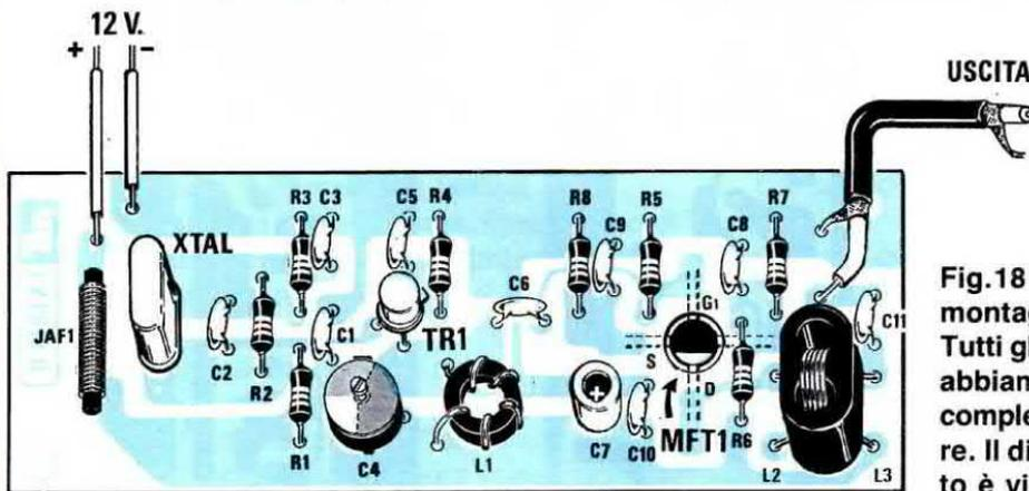
Fig.18 Schema pratico di montaggio dell'LX.1018/D. Tutti gli stadi oscillatori che abbiamo presentato sono completi di stadio separatore. Il disegno dello stampato è visibile in fig.21.
