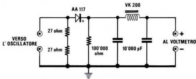
**Fig.15** Per misurare la tensione AF erogata da uno stadio oscillatore, potrete costruire questa semplice sonda rivelatrice. Il diodo rivelatore da utilizzare per questa sonda dovrà essere al GERMANIO e non al silicio.
