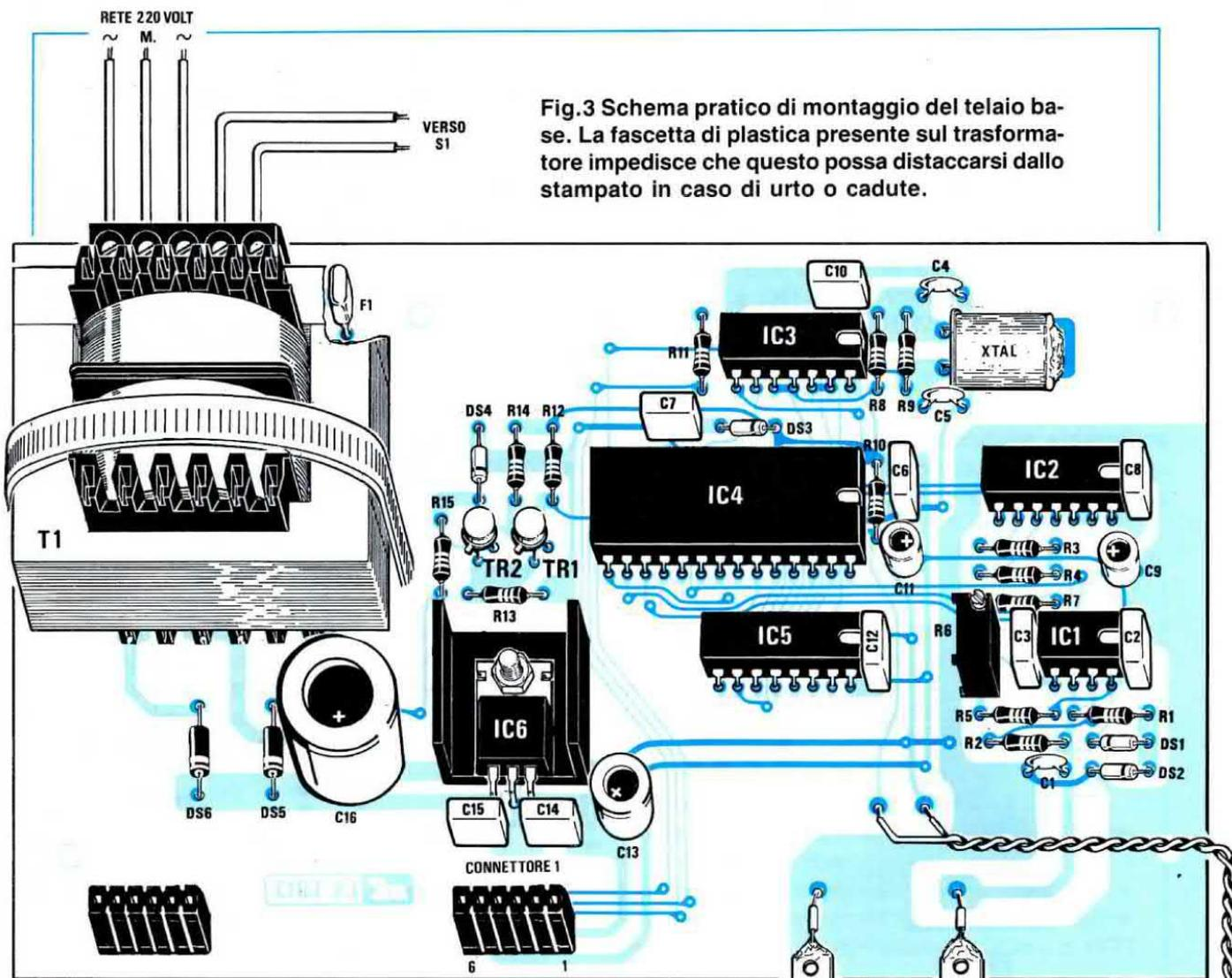
Fig.3 Schema pratico di montaggio del telaio base. La fascetta di plastica presente sul trasformatore impedisce che questo possa distaccarsi dallo stampato in caso di urto o cadute.
