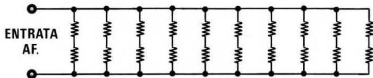
Fig.10 Per tarare il trasmettitore è necessario disporre di una resistenza di carico antiinduttiva da 50-54 ohm 20 watt circa. Poiché tale resistenza non risulta facilmente reperibile, l'abbiamo realizzata ponendo in serie ed in parallelo 20 resistenze a carbone da 270 ohm 2 watt. Sopra, lo schema elettrico di tale sonda e, di lato, la foto delle resistenze come noi le abbiamo collegate in serie ed in parallelo ad un bocchettone BNC.
