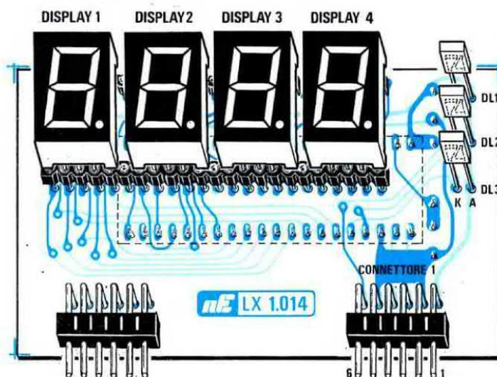
Fig.6 Schema pratico di montaggio della scheda LX.1014 vista dal lato dei display. Ricordate di rivolgere il terminale più lungo "A" dei tre diodi verso destra.
