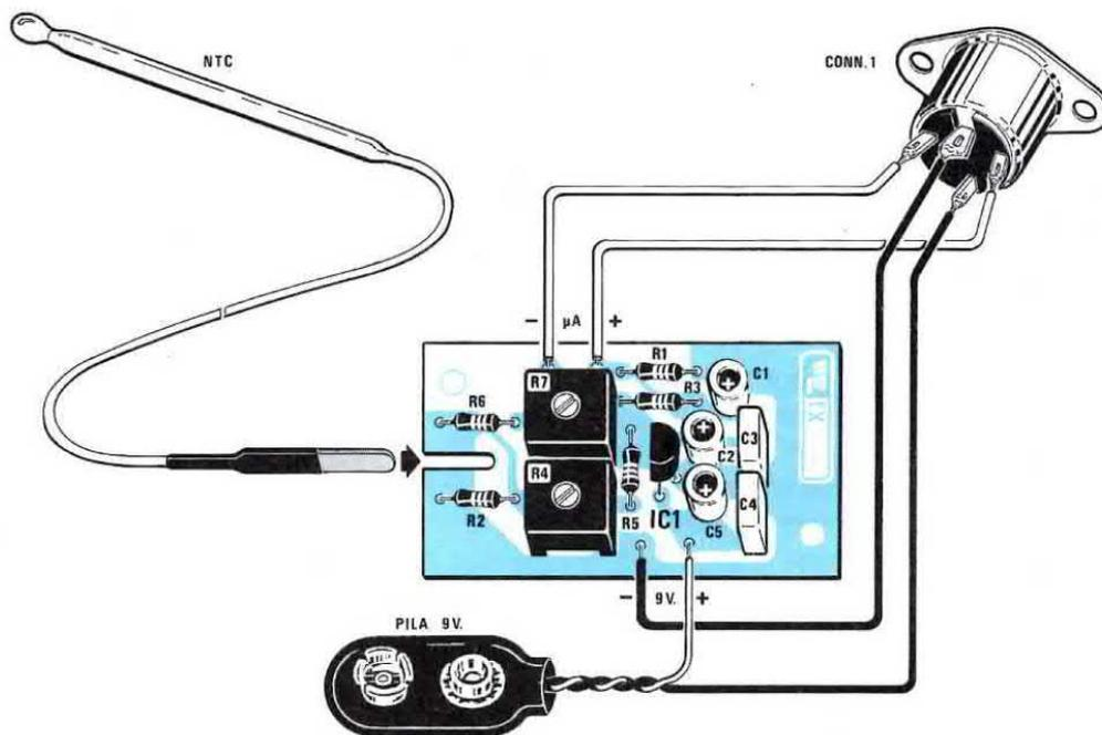
Fig.5 Schema pratico di montaggio. Si noti la fessura per l'innesto del connettore della NTC e le connessioni del CONN.1, che dovreste utilizzare per prelevare la tensione da applicare al Tester e come interruttore di rete (vedi fig.6).
