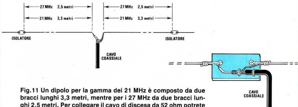
Fig.11 Un dipolo per la gamma dei 21 MHz è composto da due bracci lunghi 3,3 metri, mentre per i 27 MHz da due bracci lunghi 2,5 metri. Per collegare il cavo di discesa da 52 ohm potrete applicare al centro del dipolo un ritaglio di plexiglas o vetronite.
