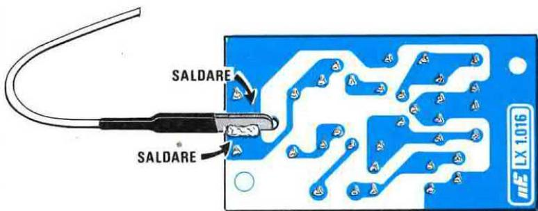
Fig.4 Disegno a grandezza naturale del circuito stampato visto dal lato rame. I due lati rame del connettore della NTC andranno saldati direttamente sulle piste dello stampato.
