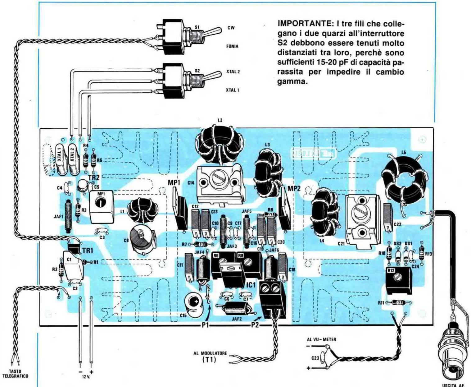
Fig.5 Schema pratico di montaggio del trasmettitore LX.1021. Dopo aver tarato il trimmer R6 e R8, i ponticelli P1-P2 andranno cortocircuitati. Se usate il trasmettitore in fonìa, dovrete collegare il trasformatore di modulazione alla morsettiera P2. In basso, la tabella con il numero di spire da avvolgere sui nuclei toroidali per la gamma 21 e 27 MHz.
