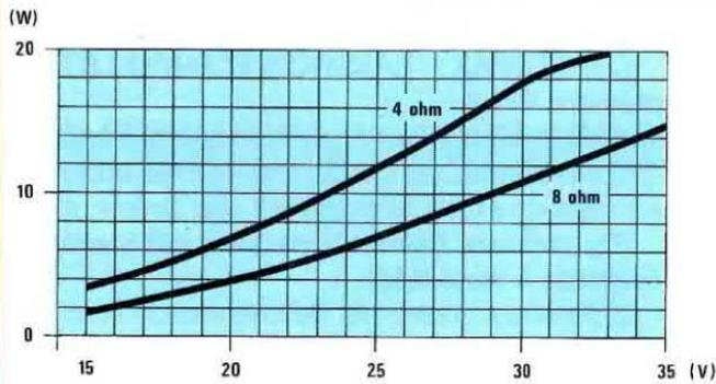
**Fig.1** Alimentando questo amplificatore con una tensione di 25 volt circa, si riescono ad ottenere 7 watt con un carico di 8 ohm e 12 watt con un carico di 4 ohm. Per avere una potenza maggiore è sufficiente elevare la tensione da 25 a 30 volt circa.
