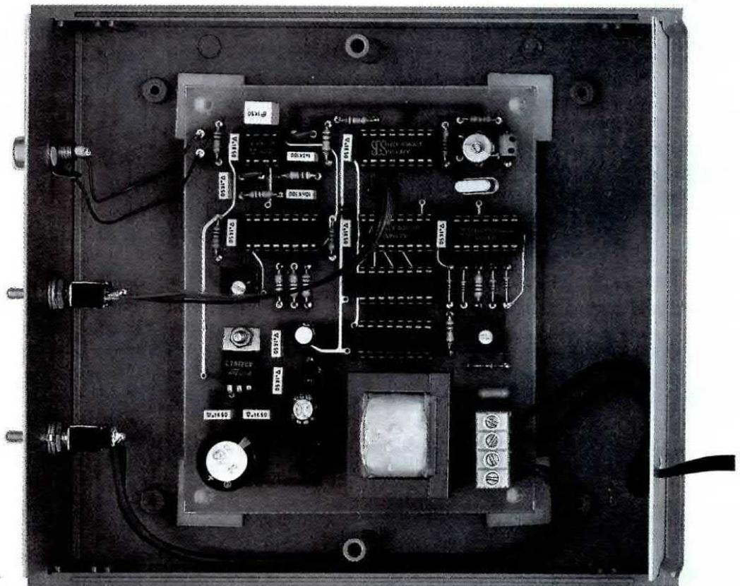
**Fig.9** Lo stampato andrà fissato all'interno del mobile con i quattro distanziatori plastici autoadesivi presenti nel kit.
