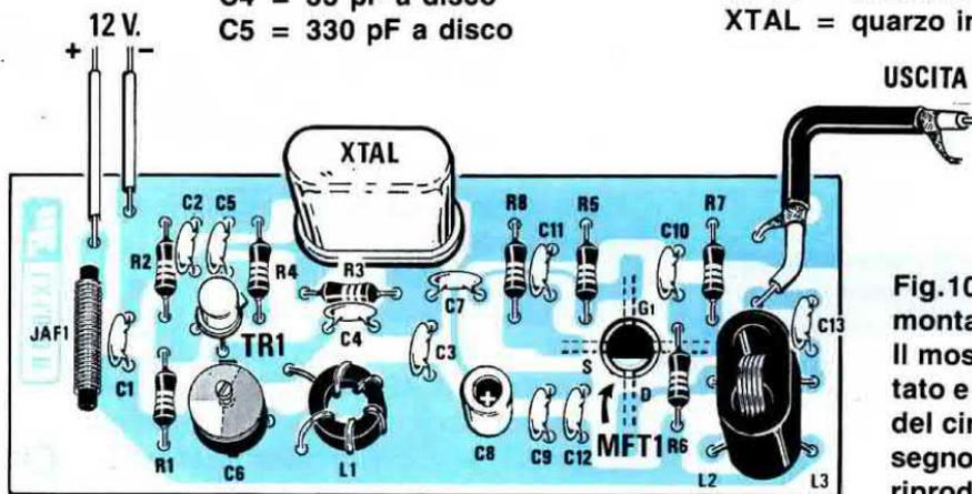
Fig.10 Schema pratico di montaggio dell'LX.1018/B. Il mosfet MFT1 viene montato e saldato sul lato rame del circuito stampato. Il disegno di questo stampato è riprodotto in fig.20.
