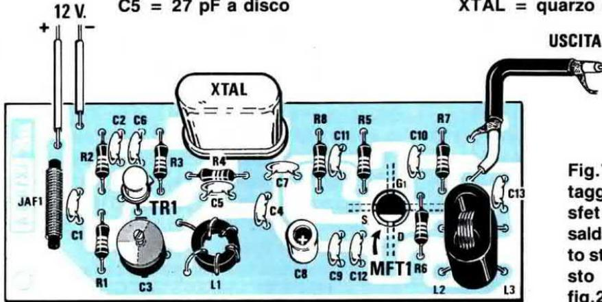
Fig.7 Schema pratico di montaggio dell'LX.1018/A. Il mosfet MFT1 viene montato e saldato sul lato rame del circuito stampato. Il disegno di questo stampato è riprodotto in fig.20.
