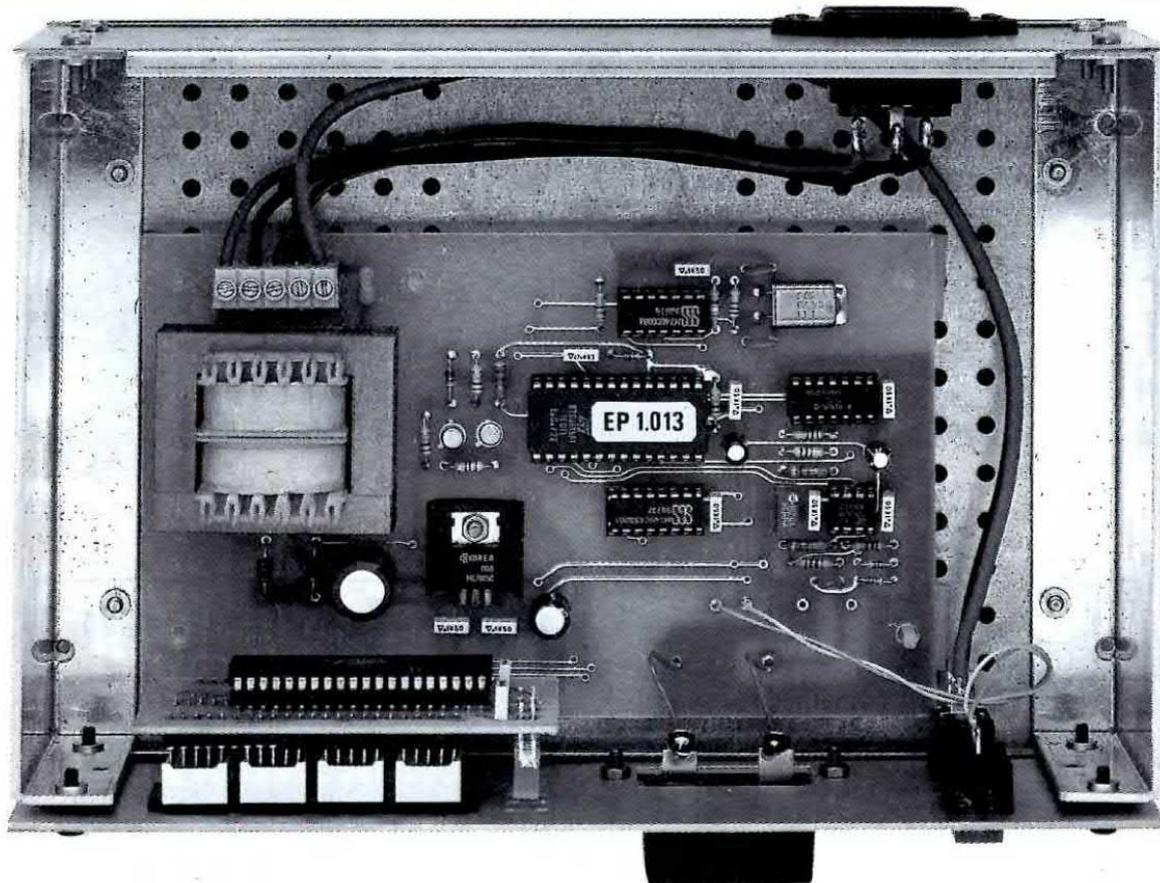
**Fig.9** In questa foto potrete notare come viene fissato all'interno del mobile lo stampato del Capacimetro. Il mobile ha le stesse dimensioni di quello dell'Impedenzimetro pubblicato nella rivista n.143/144.
