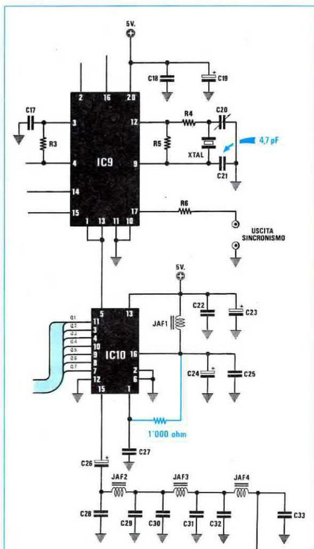
**Fig.1** Per aumentare l'ampiezza del segnale, inserite la resistenza da 1.000 ohm evidenziata in azzurro nel disegno.
