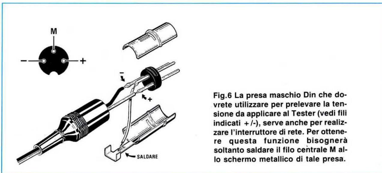
**Fig.6** La presa maschio Din che dovrete utilizzare per prelevare la tensione da applicare al Tester (vedi fili indicati +/-), serve anche per realizzare l'interruttore di rete. Per ottenere questa funzione bisognerà soltanto saldare il filo centrale M allo schermo metallico di tale presa.
