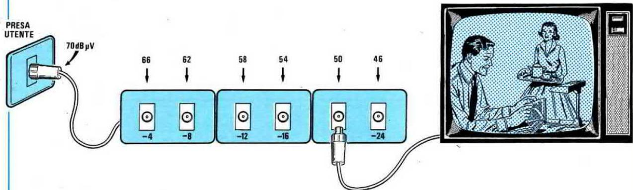
**Fig.358** Sapendo che una TV funziona correttamente quando l'ampiezza del segnale risulta compresa tra 60-80 dBmicrovolt, se nella presa di casa vostra sono presenti 70 dBmicrovolt, sullo schermo del televisore potrete vedere immagini perfette fino alla 2° presa (62 dBmicroV), ancora soddisfacenti sulla 3° presa (58 dBmicroV), ma scadenti sulla 4° presa (54 dBmicroV).
