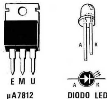
Fig.3 Disposizione dei tre terminali E-M-U dell'integrato stabilizzatore uA.7812 e dei due terminali A-K dei diodi led. Come noterete, il terminale A è riconoscibile perchè più lungo dell'opposto terminale K.
