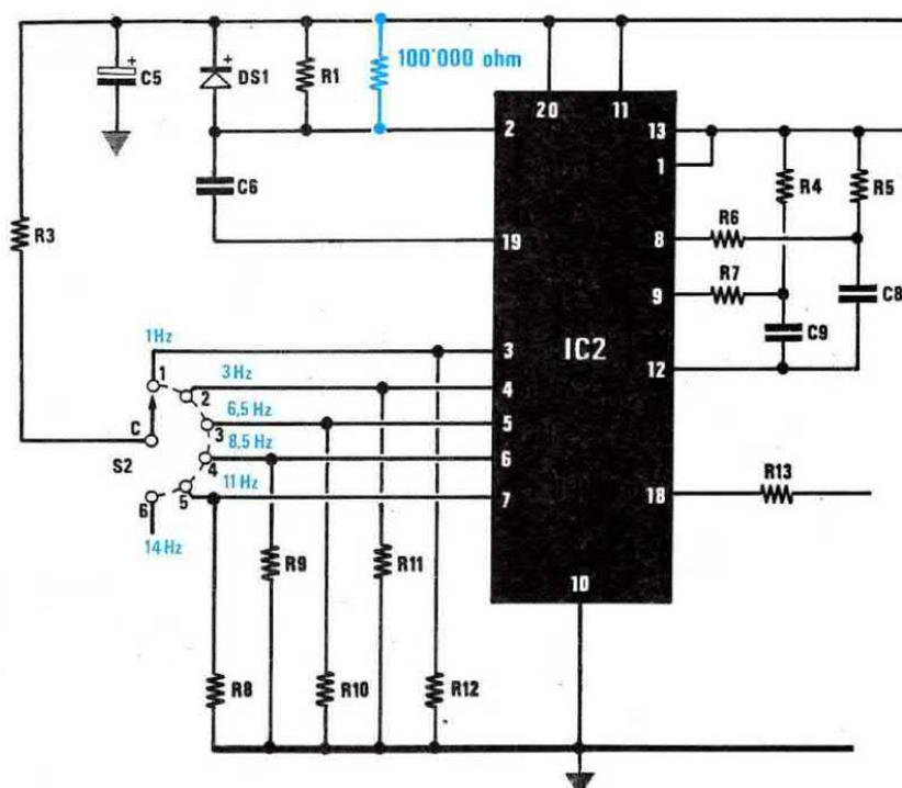
Fig.1 A chi ha inserito nella Magnetoterapia LX.950 lo stadio di potenza LX.987 e nota che il diffusore surriscalda, consigliamo di applicare sull'LX.950 una resistenza da 100.000 ohm in parallelo alla R1.
