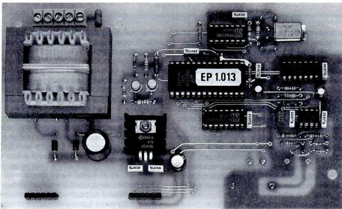
**Fig.4** Foto dello stampato con sopra già montati tutti i componenti richiesti. Nei due connettori posti in basso andrà innestato lo stampato dei display visibile nelle figg.5-7. Le piste degli stampati che vi forniremo sono protette da una speciale vernice antiossidante.
