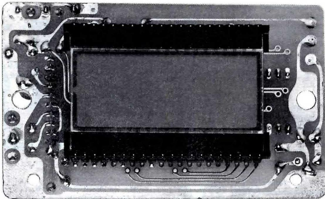
**Fig.7** Foto dello stampato visto dal lato opposto. Si noti a sinistra l'interruzione della riga nera che corre lungo il perimetro del display, utilizzata come TACCA di riferimento. Facciamo presente che sul vetro del display è presente una sottile carta autoadesiva di protezione che dovrete asportare.
