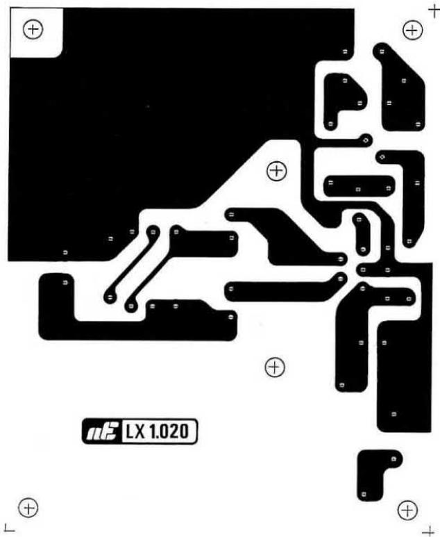
Fig.7 Schema pratico dello stadio di modulazione. Alla morsetteria collegherete il primario del trasformatore di modulazione (vedi fig.9) e al cavetto schermato indicato "Micro" la capsula microfonica preamplificata visibile in fig.3.
