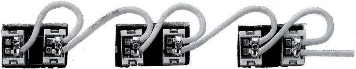
**Fig.357** Come visibile nella foto di fig.355, le prese TV andranno innestate in tre mascherine plastiche tipo Ticino che potrete reperire presso un qualsiasi negozio per elettricisti; il tutto lo potrete fissare poi sopra ad una tavoletta in legno.
