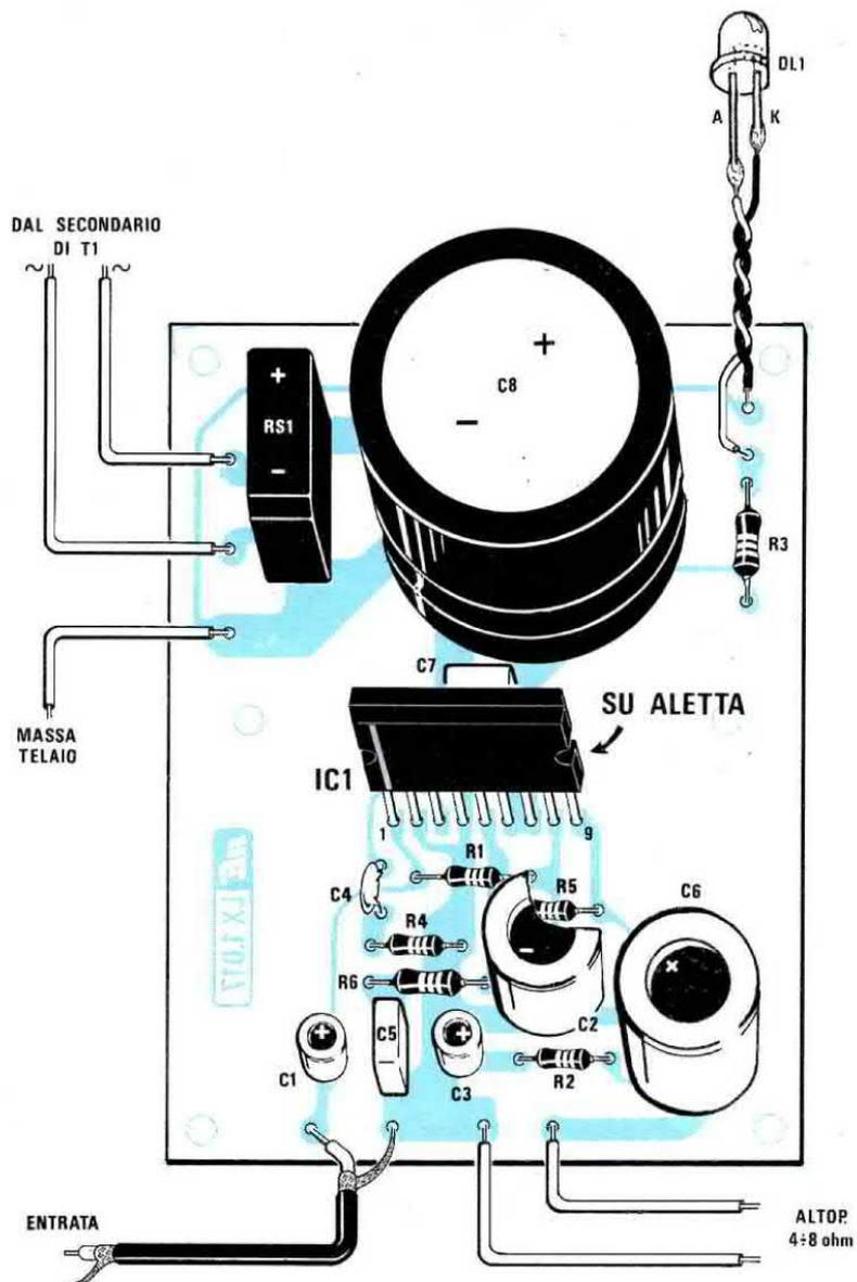
Fig.8 Schema pratico di montaggio dell'amplificatore. Per ridurre eventuali ronzii di alternata collegate il filo indicato MASSA TELAIO al metallo di un mobile. Per l'ingresso è consigliabile usare un cavetto schermato.
