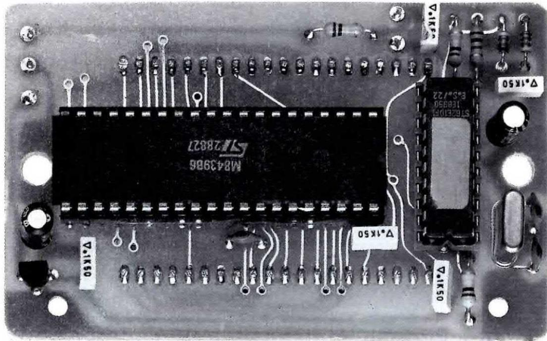
**Fig.6** Foto notevolmente ingrandita dello stampato visto dal lato dell'integrato. Lo stampato qui riprodotto non è ancora completo di vernice protettiva e di disegno serigrafico, presenti invece in quelli che vi forniremo assieme al kit.
