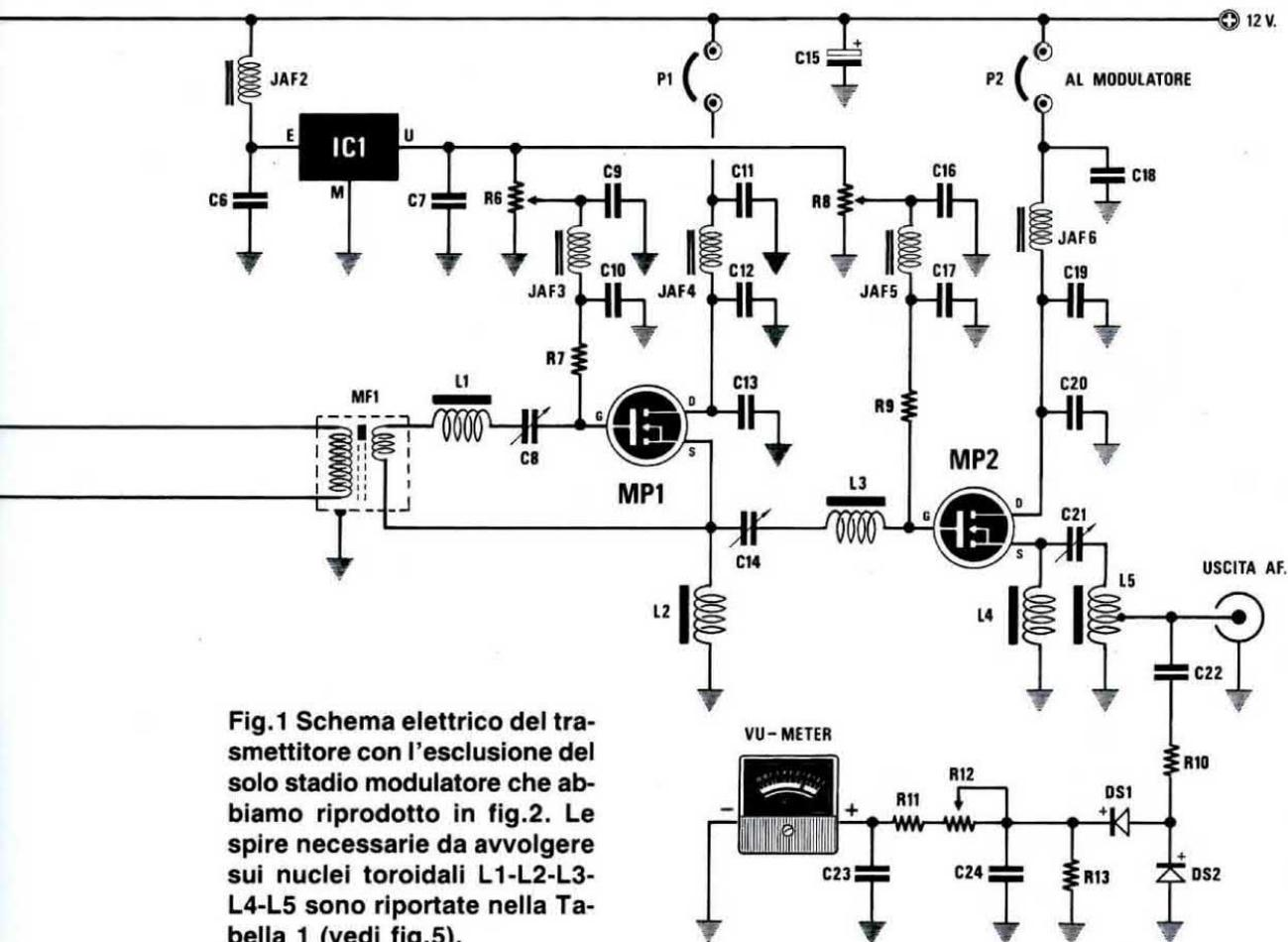
Fig.1 Schema elettrico del trasmettitore con l'esclusione del solo stadio modulatore che abbiamo riprodotto in fig.2. Le spire necessarie da avvolgere sui nuclei toroidali L1-L2-L3-L4-L5 sono riportate nella Tabella 1 (vedi fig.5).
