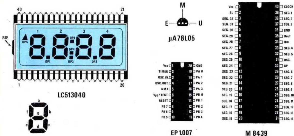
Fig.8 Connessioni del display LC.513040 e degli integrati IC1-IC3 viste da sopra e dell'integrato stabilizzatore uA.78L05 viste invece da sotto, cioè dal lato in cui i tre terminali fuoriescono dal corpo.
