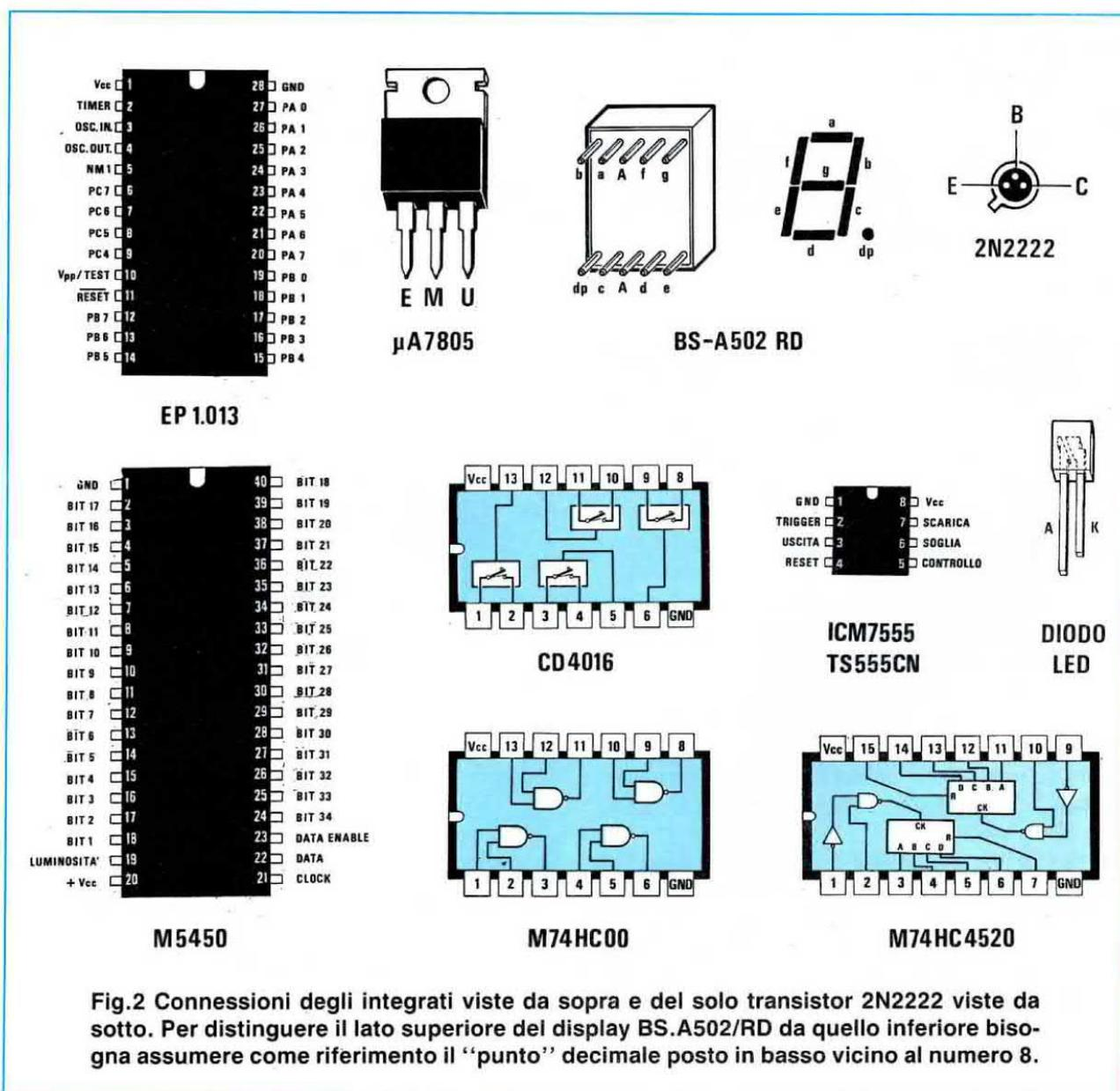
Fig.2 Connessioni degli integrati viste da sopra e del solo transistor 2N2222 viste da sotto. Per distinguere il lato superiore del display BS.A502/RD da quello inferiore bisogna assumere come riferimento il "punto" decimale posto in basso vicino al numero 8.
