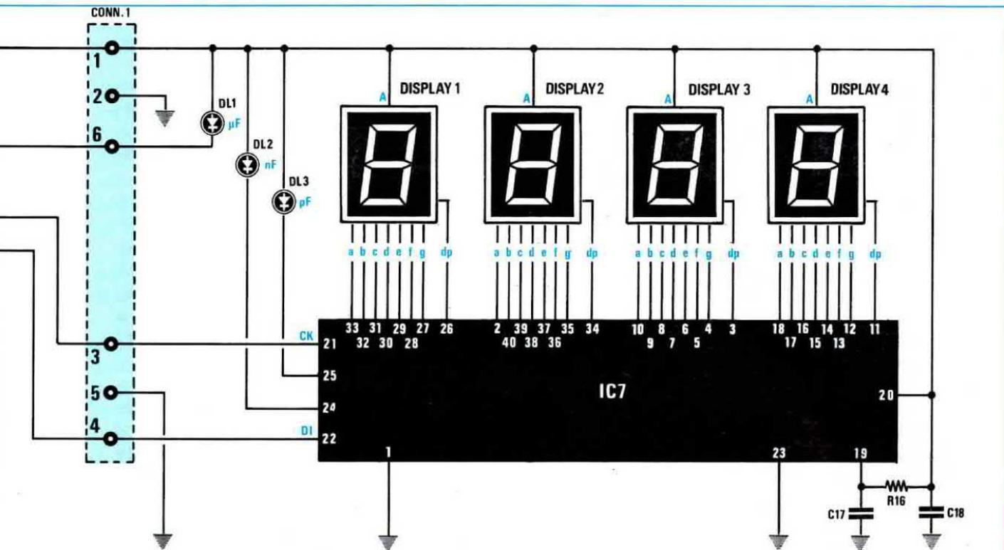
Fig.1 Schema elettrico del Capacimetro.
