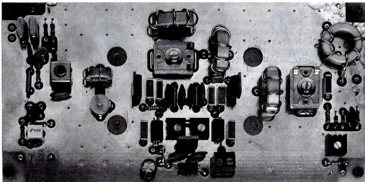
**Fig.4** Ecco come si presenterà il circuito stampato del trasmettitore, dopo che avrete montato tutti i componenti richiesti. Mancano soltanto le due alette di raffreddamento per i Mos/Power MP1 e MP2.
