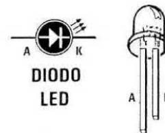
Fig.3 Osservando l'integrato frontalmente, il piedino presente a sinistra è il n.1 e quello a destra il n.9. Ricordate che il terminale più lungo del diodo led è l'Anodo ed il più corto il Catodo.
