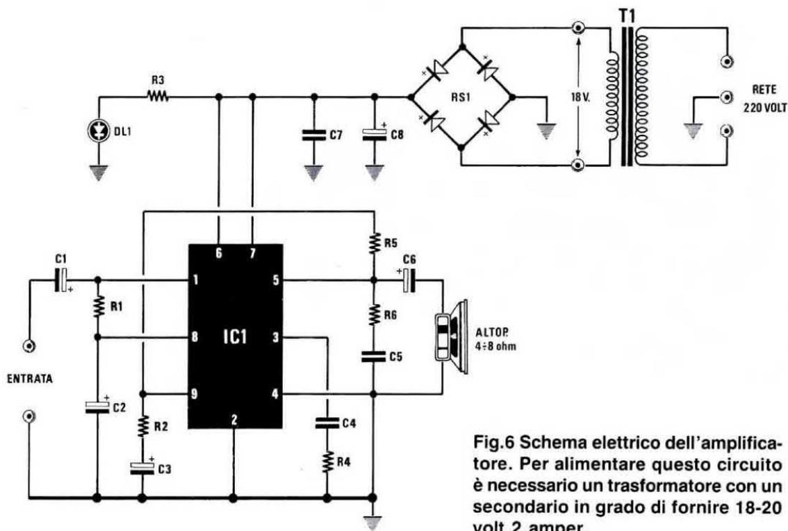
Fig.6 Schema elettrico dell'amplificatore. Per alimentare questo circuito è necessario un trasformatore con un secondario in grado di fornire 18-20 volt 2 amper.
