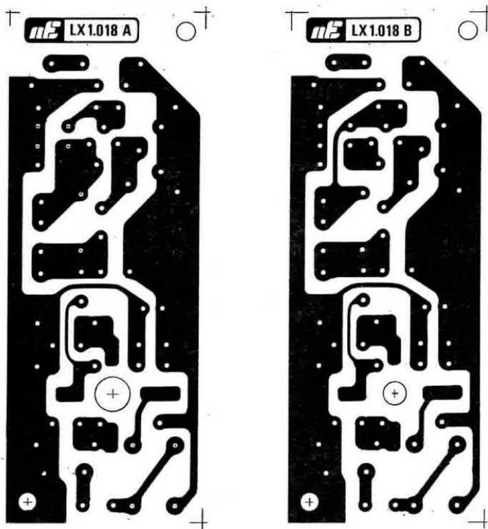
Fig.20 Disegni a grandezza naturale, visti dal lato rame, dei due stampati necessari alla realizzazione degli stadi oscillatori siglati LX.1018/A e LX.1018/B. Si consiglia di utilizzare dei supporti in fibra di vetro per ridurre al minimo le perdite di AF.
