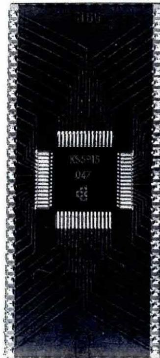
**Fig.1** All'interno dell'integrato KS.5915 sono presenti tutti gli stadi richiesti per realizzare un Voice Recording Reproducing. Purtroppo, questo integrato, dalle dimensioni di soli 14x14 millimetri, presenta ben 60 piedini, quindi se non avessimo provveduto a saldarlo sopra ad un circuito stampato più grande, nessun hobbista avrebbe mai potuto utilizzarlo. A destra, potete vedere questo minuscolo integrato saldato in tecnologia SMD sul nostro stampato.
