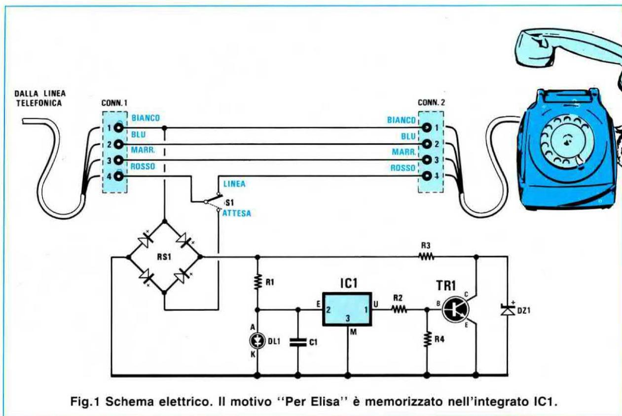
Fig.1 Schema elettrico. Il motivo "Per Elisa" è memorizzato nell'integrato IC1.
