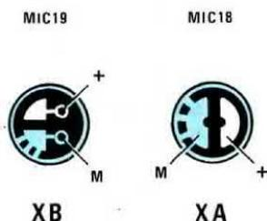
**Fig.9** Sul retro del microfono preamplificato, potrete trovare queste due diverse piste per il collegamento del filo schermato. Come noterete, la pista di "massa" è sempre collegata elettricamente alla carcassa metallica del microfono. La calza esterna del cavetto schermato andrà collegata sempre a tale pista.
