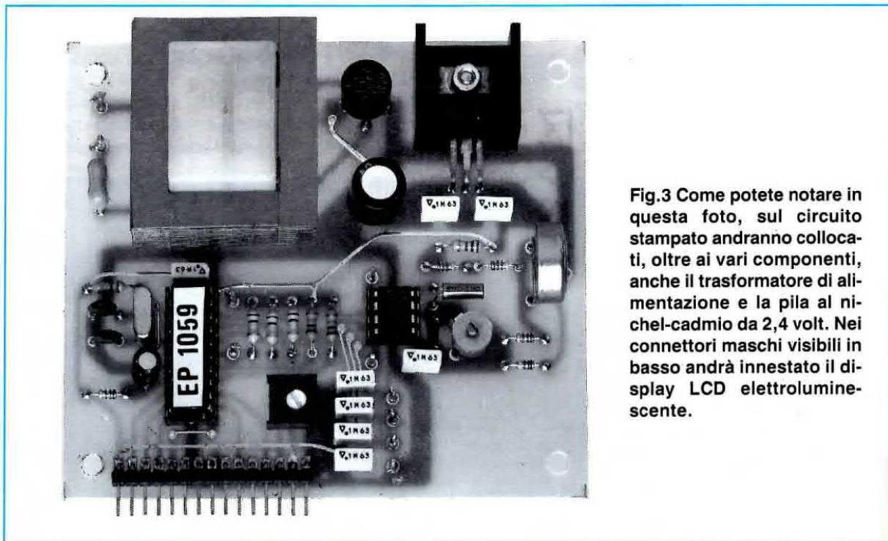
Fig.3 Come potete notare in questa foto, sul circuito stampato andranno collocati, oltre ai vari componenti, anche il trasformatore di alimentazione e la pila al nichel-cadmio da 2,4 volt. Nei connettori maschi visibili in basso andrà innestato il display LCD elettroluminescente.
