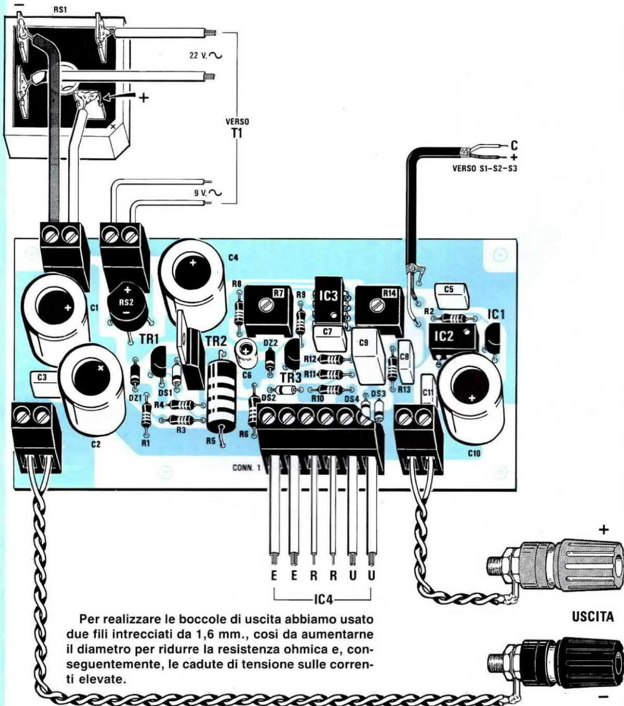
Per realizzare le bocche di uscita abbiamo usato due fili intrecciati da 1,6 mm., così da aumentarne il diametro per ridurre la resistenza ohmica e, conseguentemente, le cadute di tensione sulle correnti elevate.
