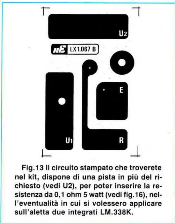
**Fig.13** Il circuito stampato che troverete nel kit, dispone di una pista in più del richiesto (vedi U2), per poter inserire la resistenza da 0,1 ohm 5 watt (vedi fig.16), nell'eventualità in cui si volessero applicare sull'aletta due integrati LM.338K.
