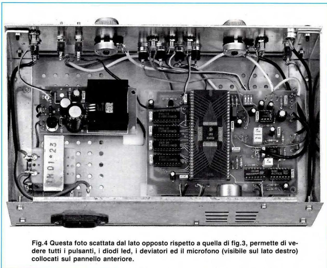
**Fig.4** Questa foto scattata dal lato opposto rispetto a quella di fig.3, permette di vedere tutti i pulsanti, i diodi led, i deviatori ed il microfono (visibile sul lato destro) collocati sul pannello anteriore.
