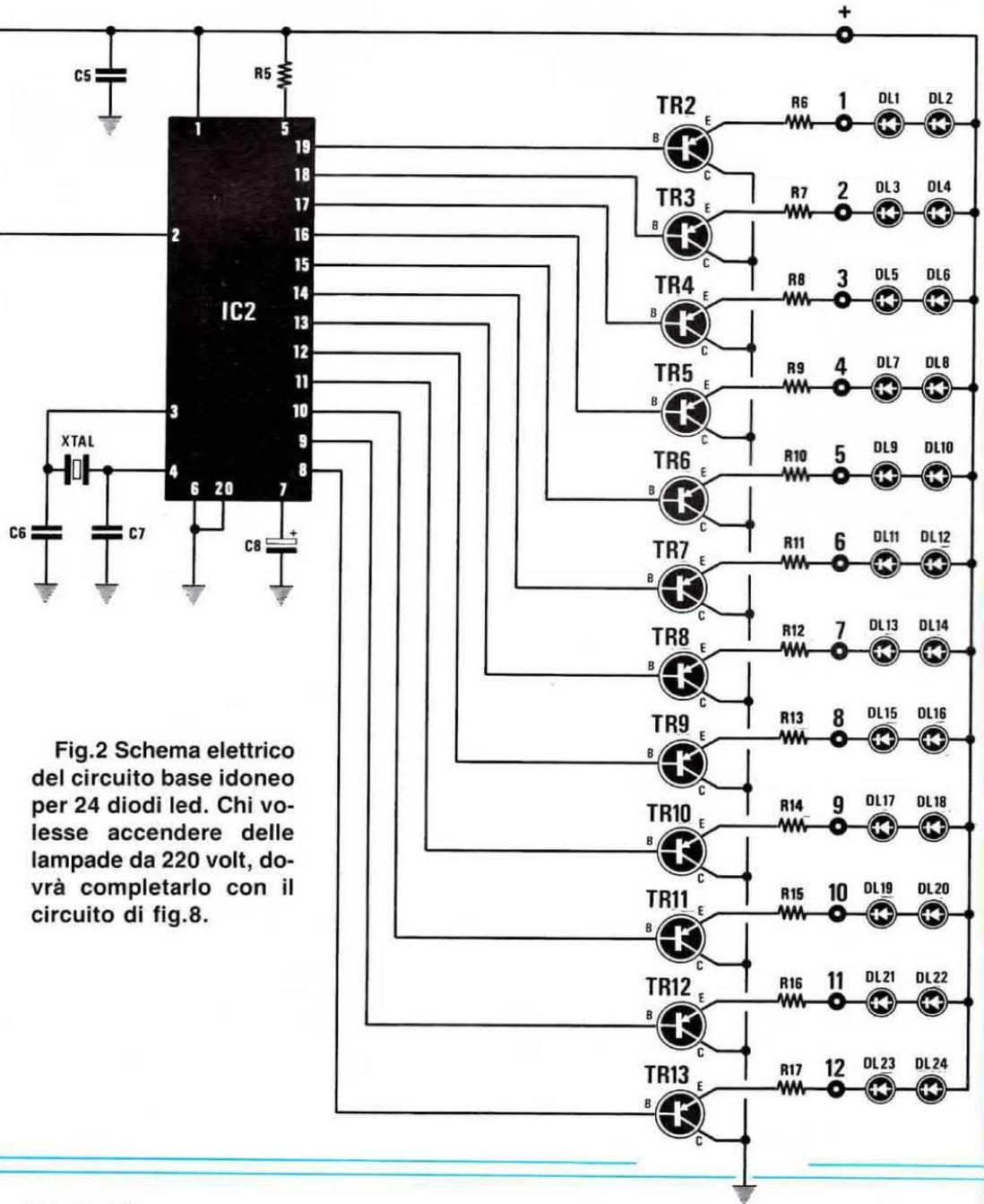
Fig.2 Schema elettrico del circuito base idoneo per 24 diodi led. Chi volesse accendere delle lampade da 220 volt, dovrà completarlo con il circuito di fig.8.
