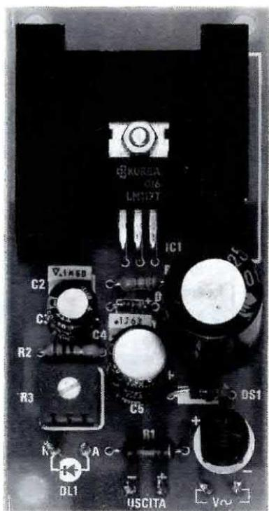
**Fig.10** Foto dello stadio di alimentazione LX.1046 così come si presenterà a montaggio ultimato. Quando richiederete questo kit, precisate che vi serve il trasformatore TN01.23 provvisto di un secondario da 9 volt, diversamente, potrete ricevere un trasformatore che eroga sul secondario una tensione maggiore.
