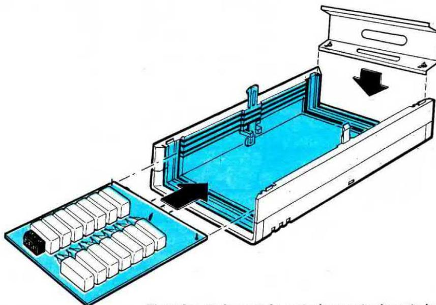
**Fig.8** Aperta la scatola, anteriormente dovete innestare la mascherina frontale sagomata a U provvista di due asole per permettere la circolazione dell'aria. Posteriormente inserirete il circuito stampato, scegliendo la guida che vi permetterà di portare le quattro punte degli aghi al centro dell'asola presente sul pannello frontale.
