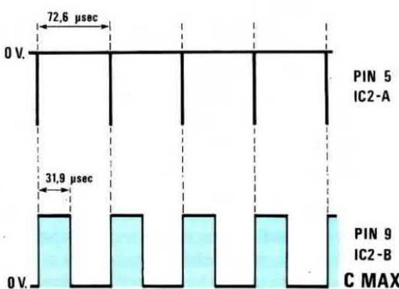
Fig.4 Con una capacità di 110 pF, vale a dire con una umidità del 10%, si otterrà un'onda quadra della durata di 24,4 microsecondi (vedi fig.3), mentre con una capacità di 144 pF, pari ad una umidità del 90%, si otterrà un'onda quadra della durata di 31,9 microsecondi.
