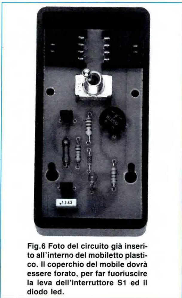
**Fig.6 Foto del circuito già inserito all'interno del mobiletto plastico. Il coperchio del mobile dovrà essere forato, per far fuoriuscire la leva dell'interruttore S1 ed il diodo led.**
