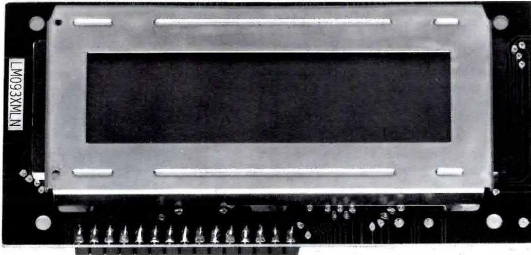
**Fig.5 Display visto anteriormente. Le dimensioni di questo display sono di 9 x 4,5 cm. In basso, si noti il connettore femmina da noi saldato in modo da poterlo innestare nel connettore maschio presente sullo stampato di fig.4.**
