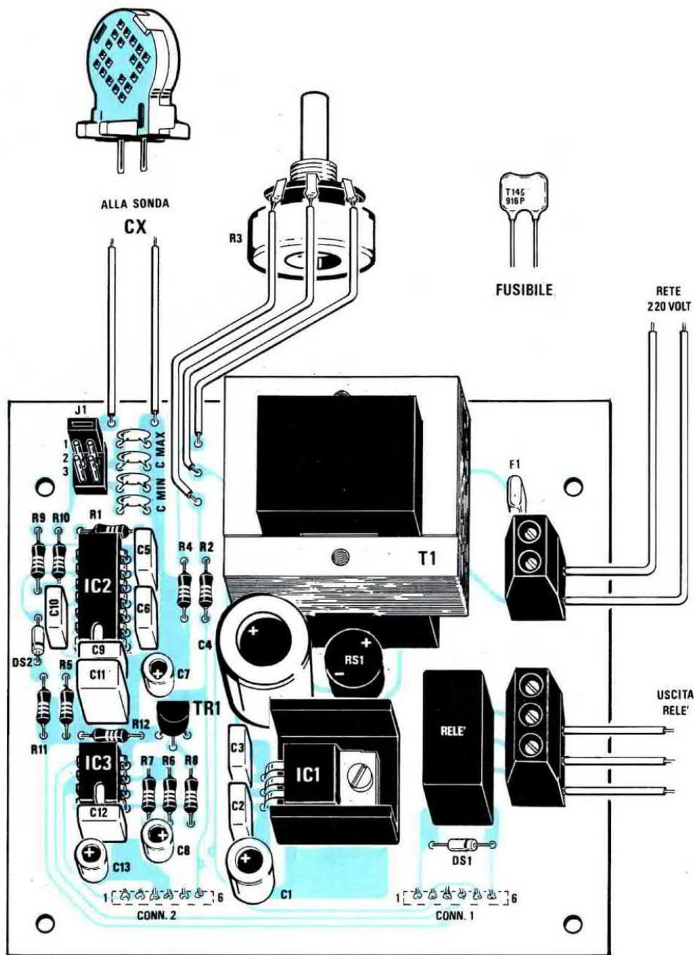
Fig.7 Schema pratico di montaggio della scheda base. Il piccolo connettore J1 (vedi in alto a sinistra) provvisto di uno spinotto di cortocircuito, servirà per inserire la sonda CX (posizione 1) oppure i condensatori di taratura per la minima e massima capacità (posizioni 2-3). Nel kit troverete due bustine con due condensatori, uno per ottenere la MINIMA capacità (circa 108-110 pF) e l'altro per la MASSIMA capacità (circa 144-146 pF), quindi fate in modo di non invertirli.
