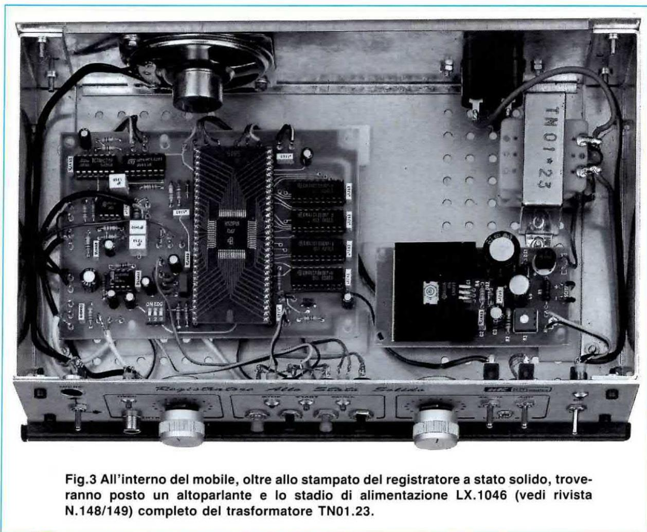
Fig.3 All'interno del mobile, oltre allo stampato del registratore a stato solido, troveranno posto un altoparlante e lo stadio di alimentazione LX.1046 (vedi rivista N.148/149) completo del trasformatore TN01.23.
