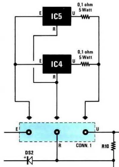
**Fig.7** Per aumentare l'erogazione della corrente d'uscita si potranno applicare due LM.338K in parallelo, non dimenticando di inserire in serie al terminale di uscita U, una resistenza a filo da 0,1 ohm 5 watt.
