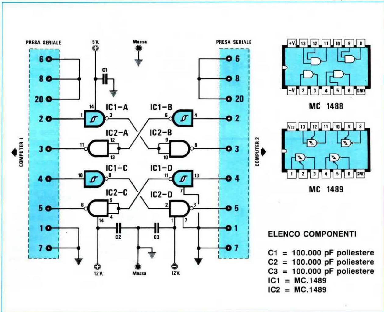
za che tali segnali saranno **bufferati**, cioè **amplificati in corrente** da IC1 per quanto riguarda i dati in uscita dal **computer 1**, e da IC2 per quanto riguarda i dati in uscita dal **computer 2**.
