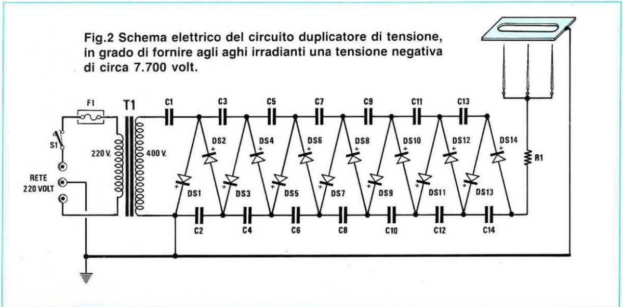
In pratica, converrebbe non superare i **40.000 ohm** di reattanza per non ritrovarsi alla fine di questi stadi duplicatori con una considerevole caduta di tensione, abbiamo scelto una capacità di **100.000 pF** (pari a 100 nanofarad), che con la frequenza di rete a **50 Hz** (pari 0,05 KHz), ci darà un valore di:
