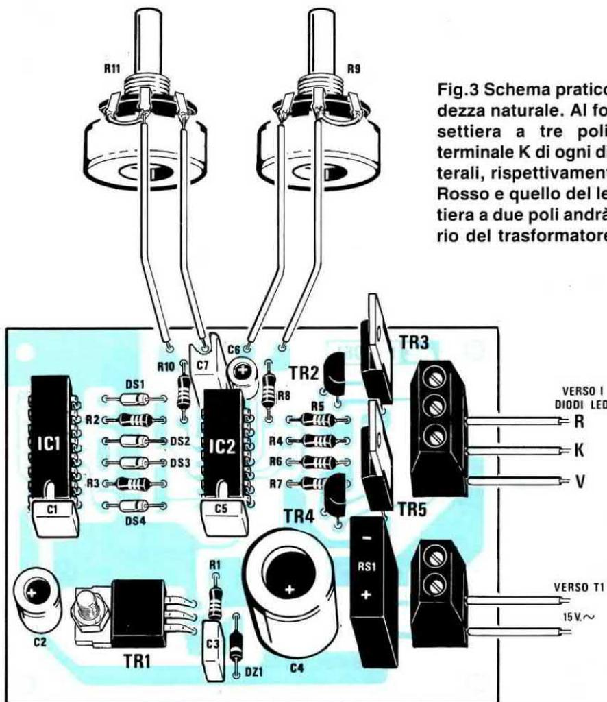
**Fig.3** Schema pratico di montaggio a grandezza naturale. Al foro centrale della morsetteria a tre poli andrà collegato il terminale K di ogni diodo, mentre ai due laterali, rispettivamente, il terminale del led Rosso e quello del led Verde. Alla morsetteria a due poli andrà collegato il secondario del trasformatore T1.
