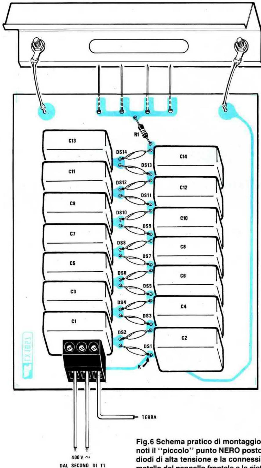
Fig.6 Schema pratico di montaggio dello stampato. Si noti il "piccolo" punto NERO posto sul solo lato K dei diodi di alta tensione e la connessione elettrica con il metallo del pannello frontale e la pista in rame che parte da DS1. Il filo indicato TERRA andrebbe collegato alla presa di "terra" della presa rete.
