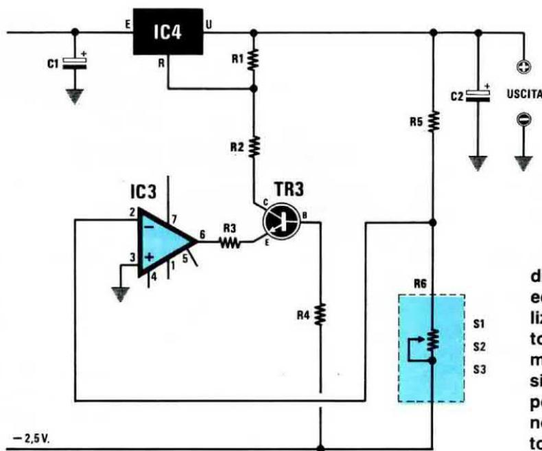
Fig.3 Aggiungendo allo schema di fig.2 un operazionale (vedi IC3) ed un transistor NPN, si potrà realizzare un alimentatore stabilizzato in grado di partire da un minimo di 0,01 volt. Per variare la tensione in uscita si dovrà agire sul potenziometro R6 sostituito, nel nostro schema, da dei commutatori digitali.
