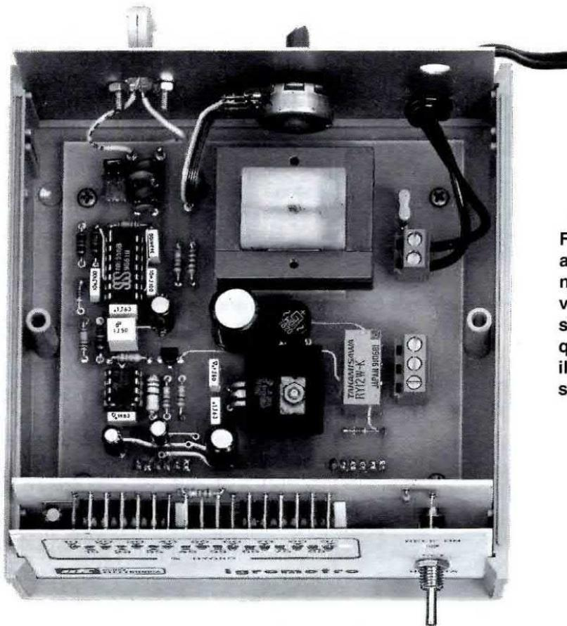
**Fig.12** Per fissare lo stadio base all'interno del mobile, dovrete innestare al suo interno lo stadio di visualizzazione, poi appoggiare sui diodi led il pannello frontale, quindi far scendere il pannello e il circuito stampato entro le due scanalature del mobile.
