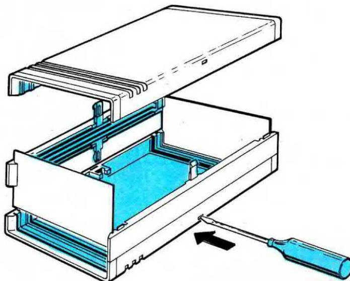
**Fig.7** Il mobile per questo ionodepuratore è un modello deluxe di colore grigio perla, provvisto internamente di guide laterali per l'innesto del circuito stampato. Per aprire i due gusci del mobile sarà sufficiente premere all'interno delle due fessure laterali con la lama di un cacciavite per sganciare la levetta del fermo.
