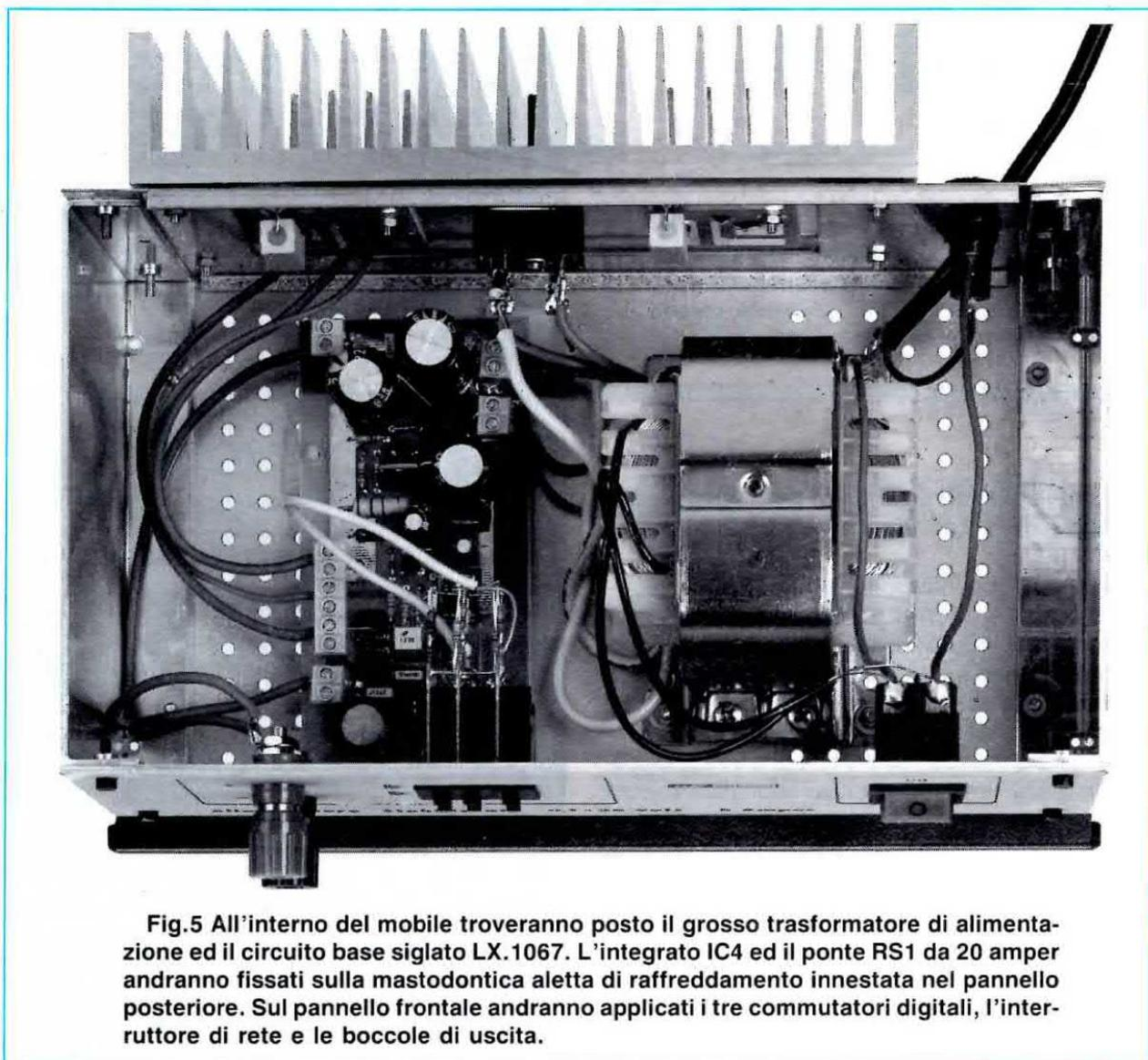
Fig.5 All'interno del mobile troveranno posto il grosso trasformatore di alimentazione ed il circuito base siglato LX.1067. L'integrato IC4 ed il ponte RS1 da 20 amper andranno fissati sulla mastodontica aletta di raffreddamento innestata nel pannello posteriore. Sul pannello frontale andranno applicati i tre commutatori digitali, l'interruttore di rete e le bocche di uscita.
