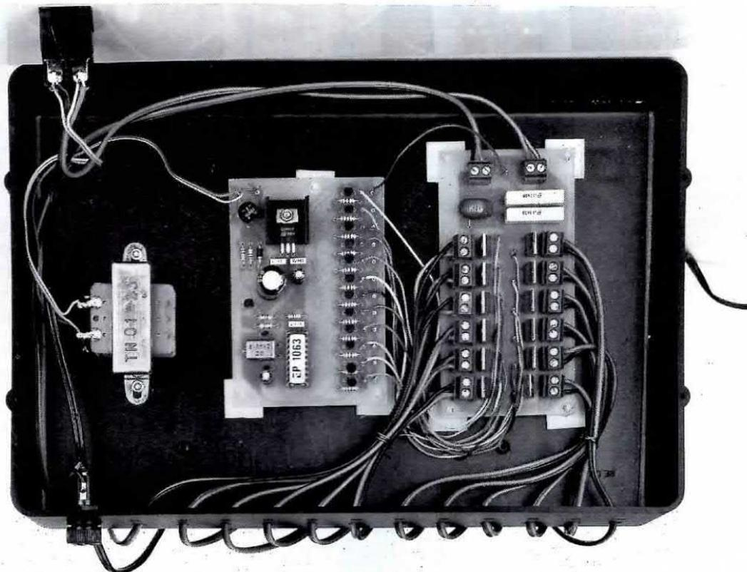
Fig.11 In alto, la foto del circuito LX.1064 montato e qui sotto la foto dei due circuiti LX.1063-LX.1064 e del trasformatore di alimentazione fissati sulla base del mobile plastico.
