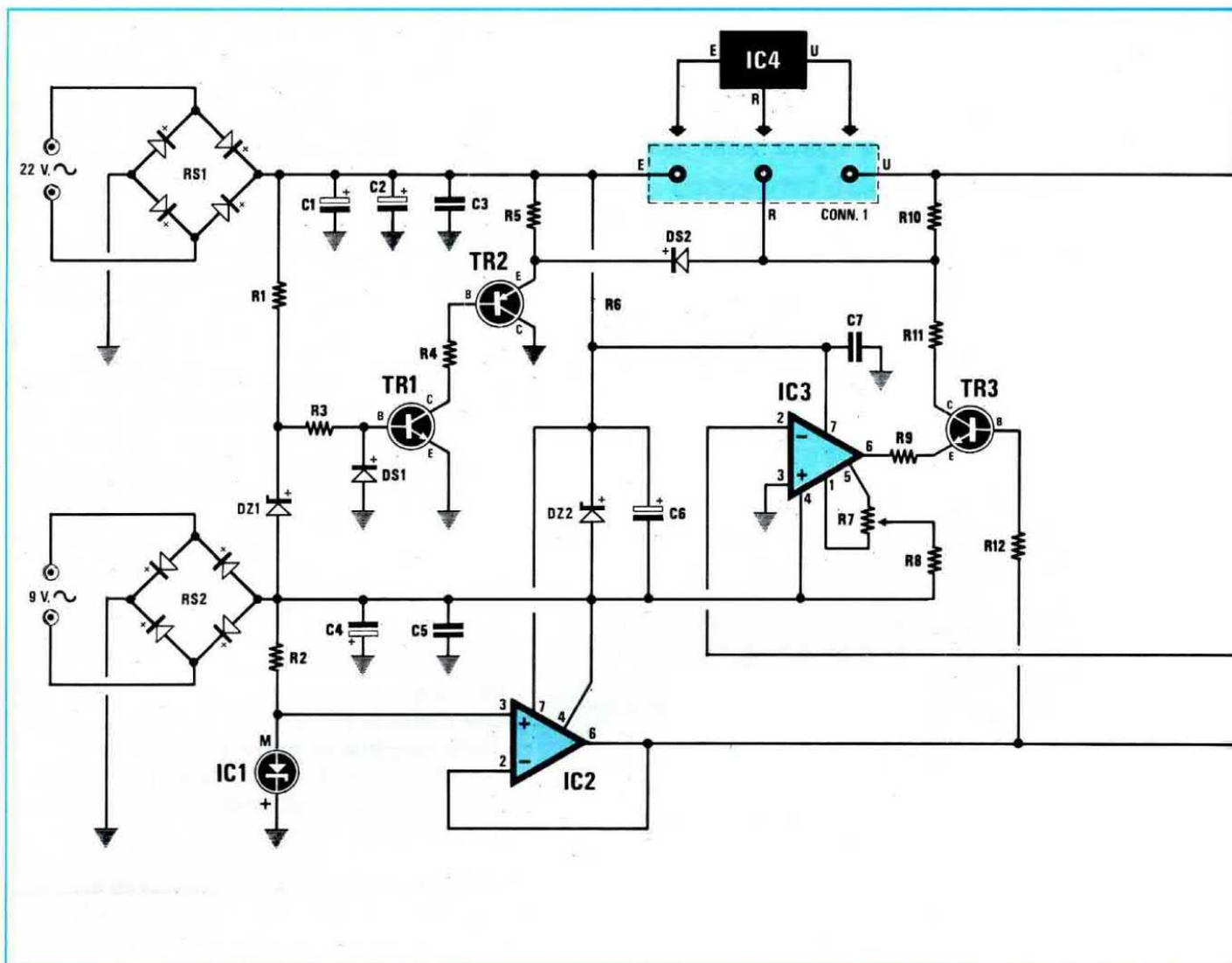
Il secondo ponte raddrizzatore **RS2** servirà per raddrizzare una tensione di **9 volt 0,5 amper**, che preleveremo sempre da T1 e che utilizzeremo per ricavare quella tensione **negativa**, necessaria per alimentare i piedini 4 dei due operazionali IC2-IC3. Tramite l'integrato IC1, dalla forma e dalle dimensioni di un piccolo transistor, questa tensione **negativa** verrà stabilizzata sui **2,5 volt**.
