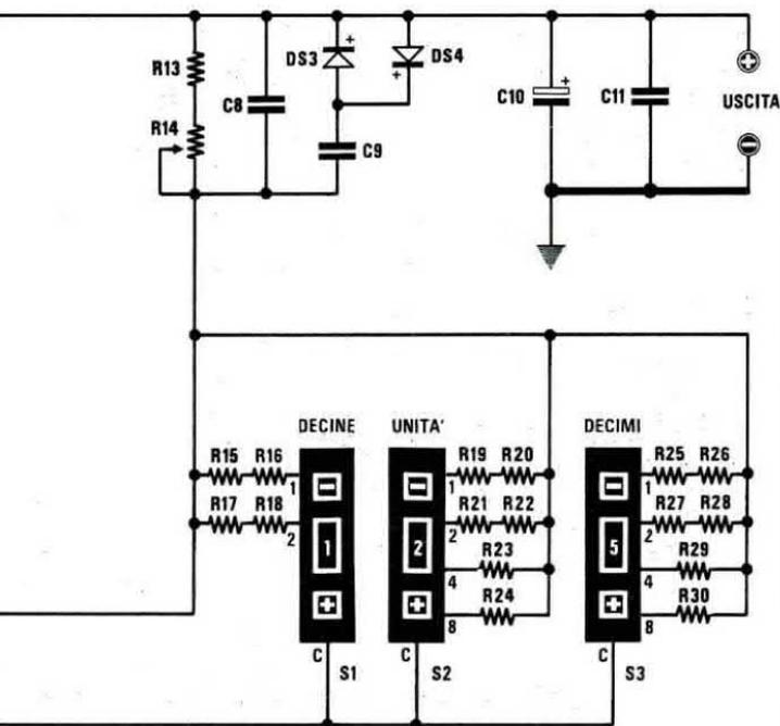
Fig.4 Schema elettrico completo del nostro alimentatore stabilizzato. I tre commutatori digitali S1-S2-S3 sostituiscono il potenziometro siglato R6, presente invece nello schema precedente (vedi fig.3).
