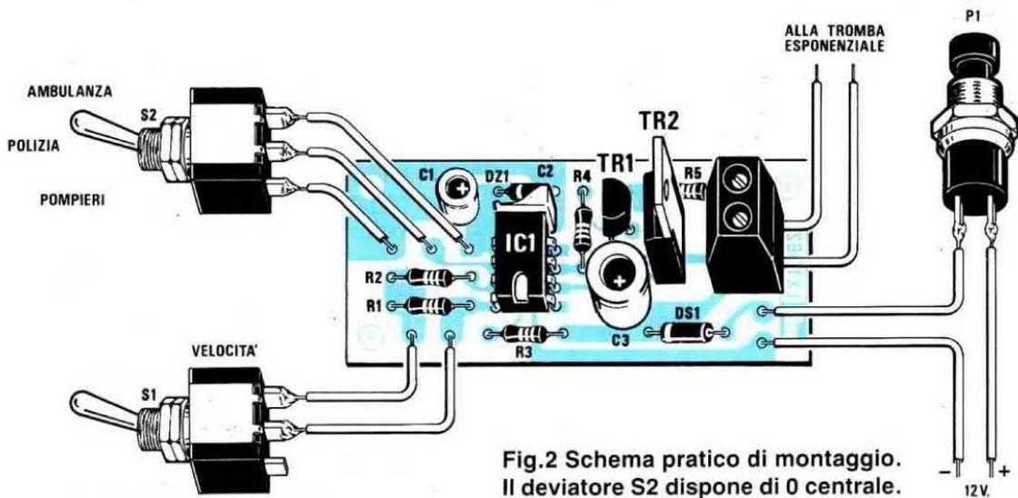
Fig.2 Schema pratico di montaggio. Il deviatore S2 dispone di 0 centrale.
