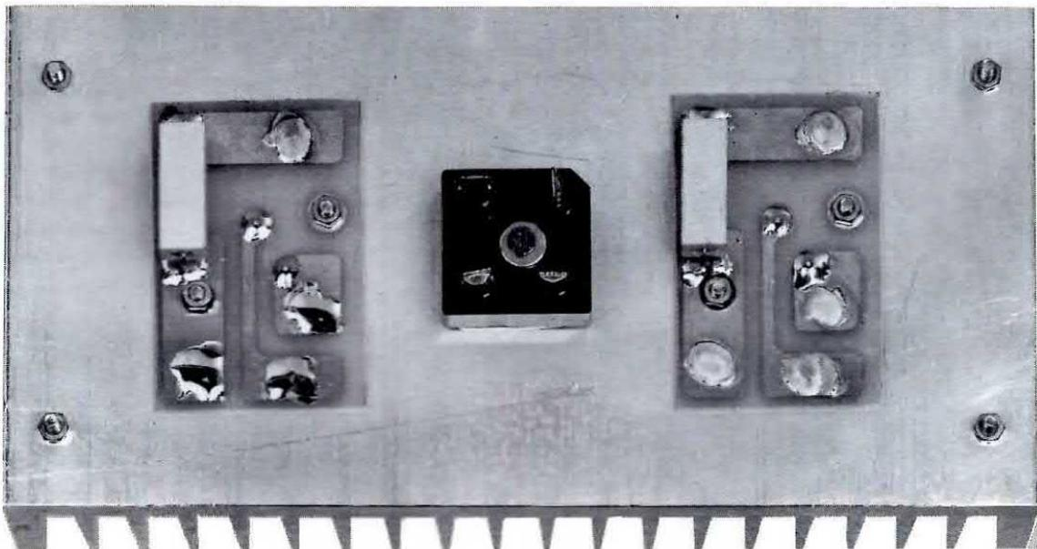
Fig.17 L'aletta di raffreddamento da noi fornita, risulta già forata per ricevere una coppia di LM.338K (vedi fig.15), quindi come potete vedere in questa foto, i due integrati andranno fissati ai suoi lati, mentre al centro andrà applicato il ponte raddrizzatore da 20 amper. Se si prelevano a regime continuo correnti superiori a 8-9 amper, conviene raffreddare l'aletta con una ventola assiale.
