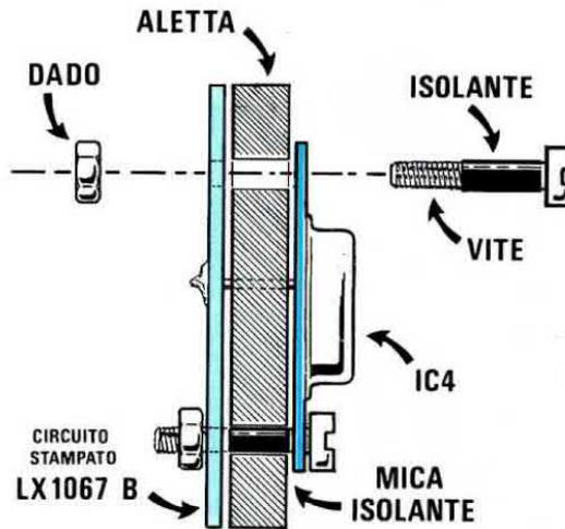
Fig.14 Se userete un solo LM.338K, dovrete collegare i fili U-E-R prelevati dalla morsettiera (vedi fig.9) alle piste in rame U1-E-R. Quando fisserete l'integrato sull'aletta, non dimenticatevi di isolarlo con la mica che troverete inclusa nel kit.
