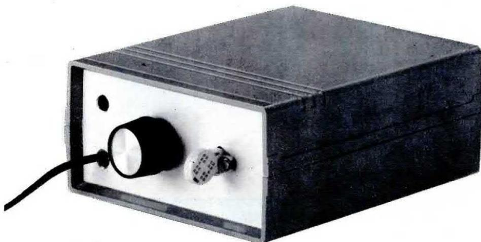
**Fig.5** La sonda Philips da noi indicata nello schema elettrico con la sigla **CX**, verrà applicata in senso verticale sul pannello posteriore del mobile. Sempre sul pannello posteriore verrà applicato il potenziometro **R3**, necessario per eccitare o diseccitare il relè sulla percentuale di umidità da noi prescelta, in modo da mettere in azione un allarme oppure un ventilatore o un vaporizzatore.
