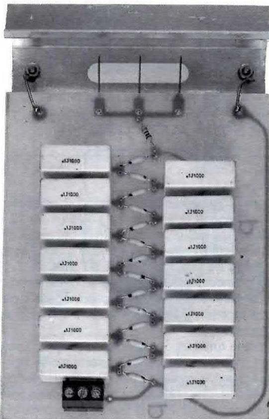
Fig.4 Foto dello stampato con sopra già montati tutti i condensatori ed i diodi, e con la mascherina frontale già collegata alla pista del positivo per mezzo di uno spezzone di filo di rame.
