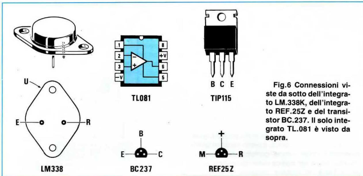
Fig.6 Connessioni viste da sotto dell'integrato LM.338K, dell'integrato REF.25Z e del transistor BC.237. Il solo integrato TL.081 è visto da sopra.
