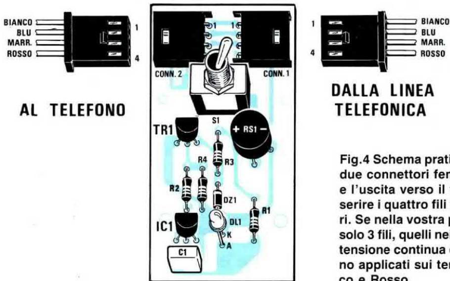
Fig.4 Schema pratico di montaggio. Nei due connettori femmina per l'ingresso e l'uscita verso il telefono, dovrete inserire i quattro fili rispettandone i colori. Se nella vostra presa interna vi sono solo 3 fili, quelli nei quali è presente una tensione continua di 40-48 volt, andranno applicati sui terminali indicati Bianco e Rosso.
