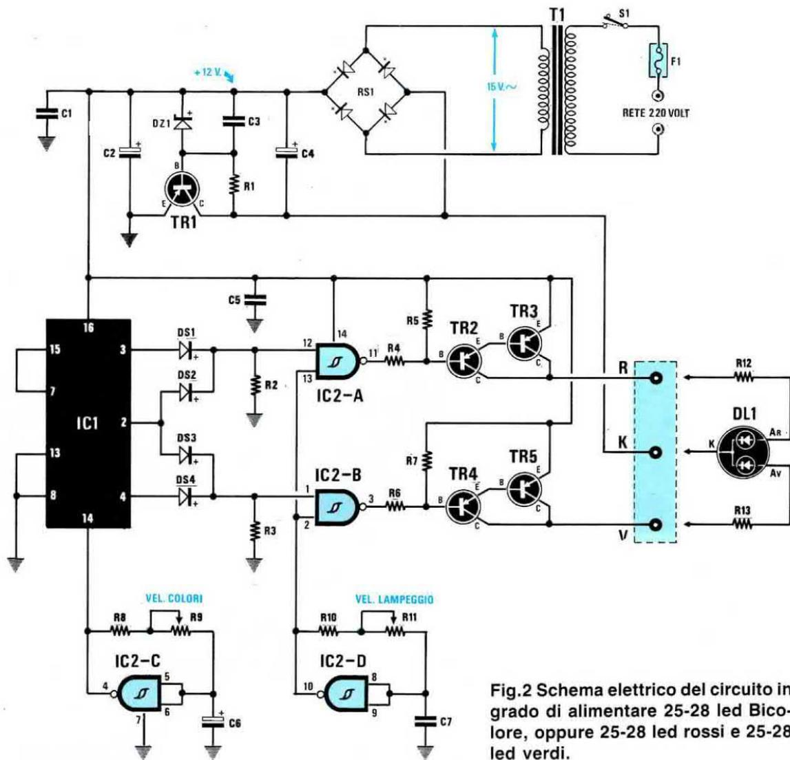
Fig.2 Schema elettrico del circuito in grado di alimentare 25-28 led Bicolore, oppure 25-28 led rossi e 25-28 led verdi.
