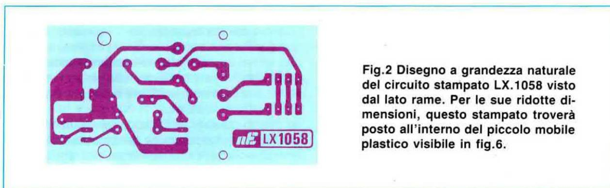
Fig.2 Disegno a grandezza naturale del circuito stampato LX.1058 visto dal lato rame. Per le sue ridotte dimensioni, questo stampato troverà posto all'interno del piccolo mobile plastico visibile in fig.6.
