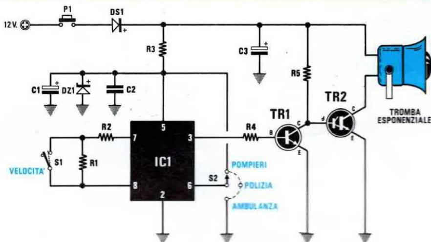
Fig.1 Schema elettrico della sirena a tre suoni.
