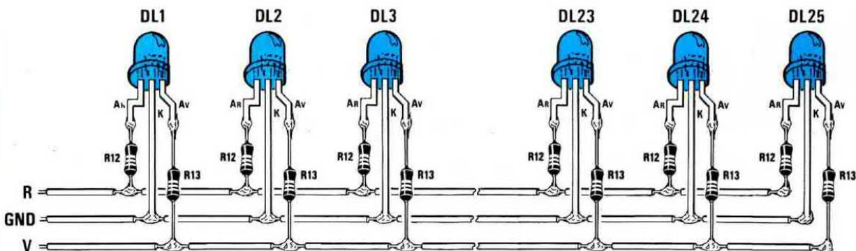
**Fig.7** Presso un elettricista potrete acquistare del filo isolato in plastica di colore diverso e della lunghezza richiesta, e, una volta attorcigliato su se stesso, potrete saldarvi sopra il Catodo e le due resistenze da 680 ohm che abbiamo siglato R12 e R13.
