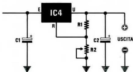
Fig.1 La soluzione più semplice per realizzare un alimentatore stabilizzato con un LM.338K, è quella di applicare un potenziometro tra il terminale R e la massa. Con un simile schema non si potrà mai scendere su tensioni stabilizzate inferiori agli 1,25 volt.
