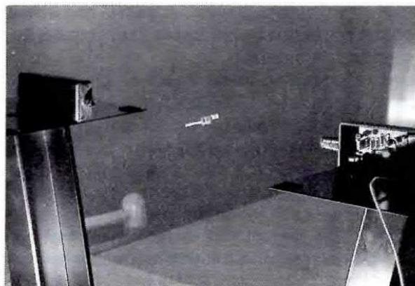
In laboratorio è possibile effettuare delle foto di oggetti in movimento. In questa foto si vede al centro un "transistor" in caduta fotografato nell'istante in cui interrompe il fascio a raggi infrarossi. Con questo sistema si può fotografare il passaggio di una farfalla o la caduta di un gatto.
