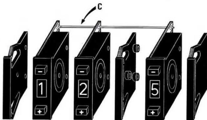
Fig.11 Ai lati dei tre commutatori binari andranno applicate le due sponde laterali, mentre tra i due commutatori di sinistra e quello di destra andrà inserita una sponda separatrice, a segnalare che il numero di destra indica i decimali di volt.
