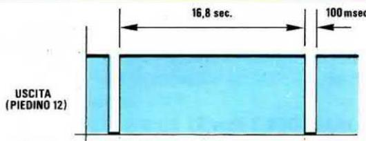
**Fig.4** Terminata la carica, se non togliere la pila, l'integrato automaticamente passerà nella funzione "carica di mantenimento", cioè provvederà ad inviare un impulso di carica della durata di 100 millisecondi seguito da una pausa di circa 16,8 secondi.
