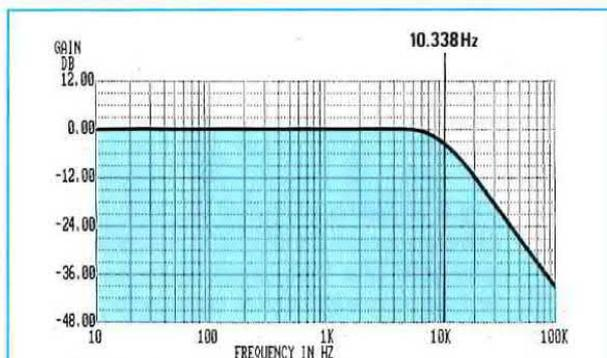
**Fig.2** I filtri Passa/Basso vengono utilizzati per lasciar passare tutte le frequenze inferiori alla loro frequenza di TAGLIO. In questo grafico abbiamo un filtro Passa/Basso calcolato sui 10.338 Hz, pertanto, la prima ottava superiore a 20.676 Hz subirà un'attenuazione di 12 dB.
