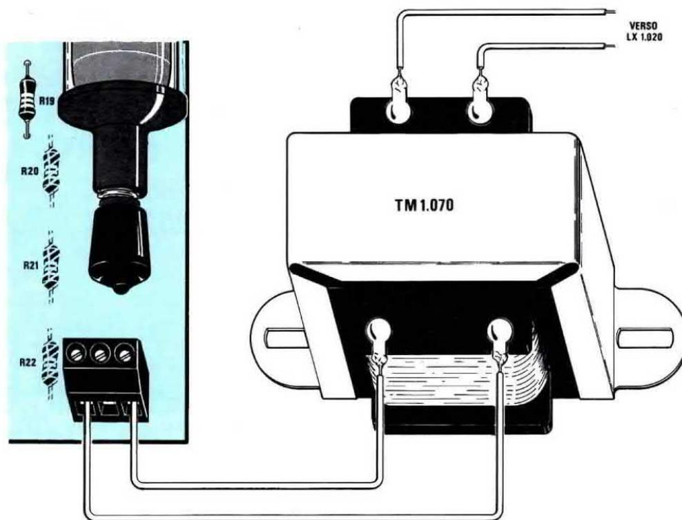
Fig.1 Per modulare il Laser LX.1070 presentato su questo stesso numero, sarà sufficiente collegare il secondario del trasformatore TM.1070 (vedi i due terminali più distanziati) alla morsettiera posta dietro al tubo Laser. Al primario di tale trasformatore (vedi i due terminali più ravvicinati) andrà collegata l'uscita del kit LX.1020 (vedi fig.2) presentato nella rivista n.145.
