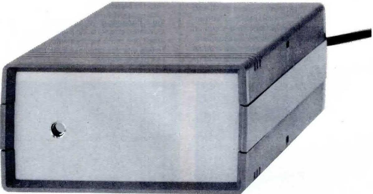
**Fig.12** All'interno di un elegante mobile plastico troverà posto l'intero circuito, compreso il tubo Laser. Per far fuoriuscire il fascio luminoso, si dovrà praticare un foro del diametro di circa 8 mm. sul pannello frontale di alluminio in corrispondenza del tubo.
