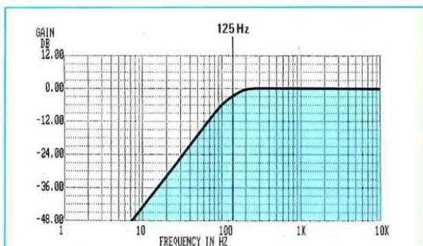
**Fig.1** I filtri Passa/Alto vengono utilizzati per lasciar passare tutte le frequenze superiori alla loro frequenza di TAGLIO. In questo grafico abbiamo un filtro Passa/Alto calcolato sui 125 Hz, pertanto, la prima ottava inferiore a 62,5 Hz subirà un'attenuazione di 12 dB.
