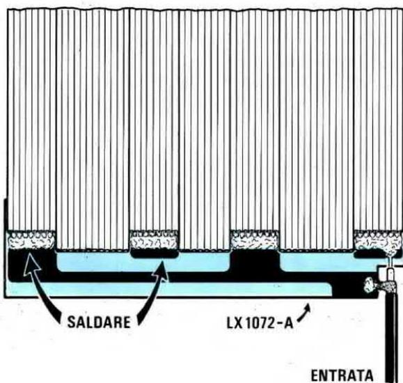
**Fig.6** Disegno pratico dei collegamenti della piattina e del cavo coassiale d'entrata sul circuito stampato siglato LX.1072/A. Dei 64 fili da cui è composta questa piattina, andranno saldati sulle piste dello stampato - 8 fili SI - 12 no - 8 SI - 8 no - 8 SI - 12 no - 8 SI. **NOTA:** se salderete per errore 7 fili anziché 8, l'efficacia della fascia verrà alterata.
