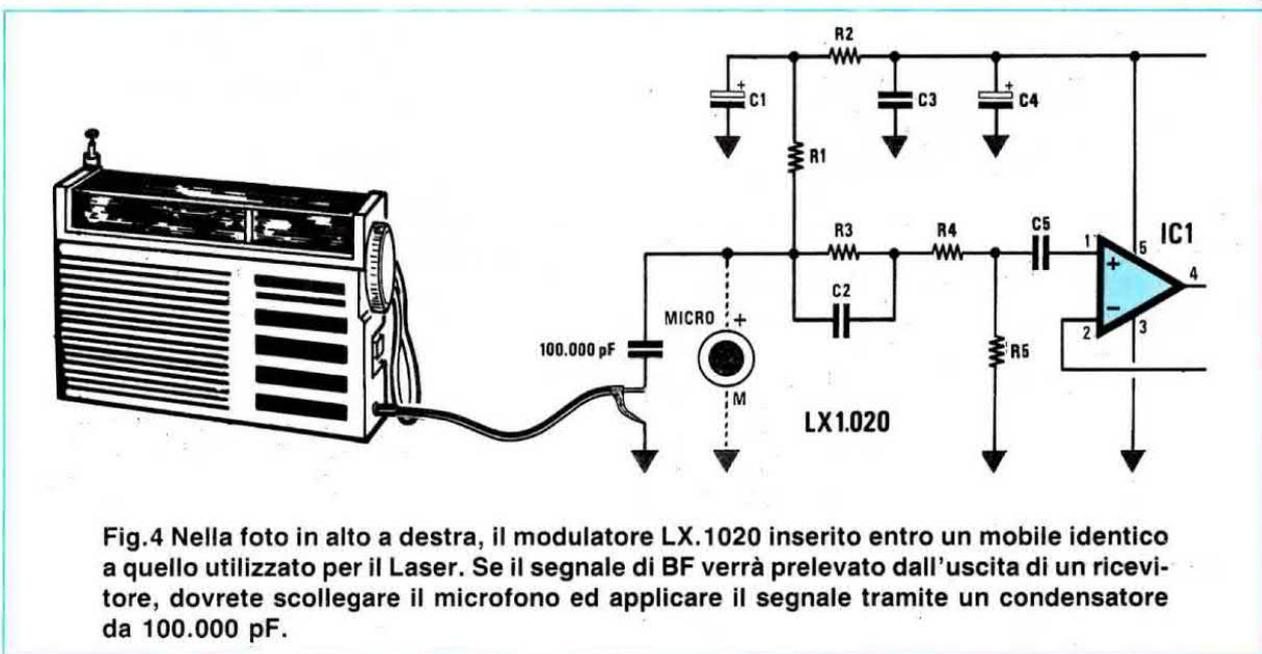
Fig.4 Nella foto in alto a destra, il modulatore LX.1020 inserito entro un mobile identico a quello utilizzato per il Laser. Se il segnale di BF verrà prelevato dall'uscita di un ricevitore, dovrete scollegare il microfono ed applicare il segnale tramite un condensatore da 100.000 pF.
