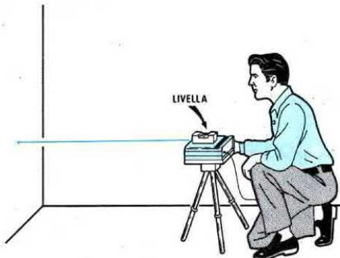
Fig.2 Il Laser può servire anche per tracciare dei punti di riferimento perfettamente livellati.
