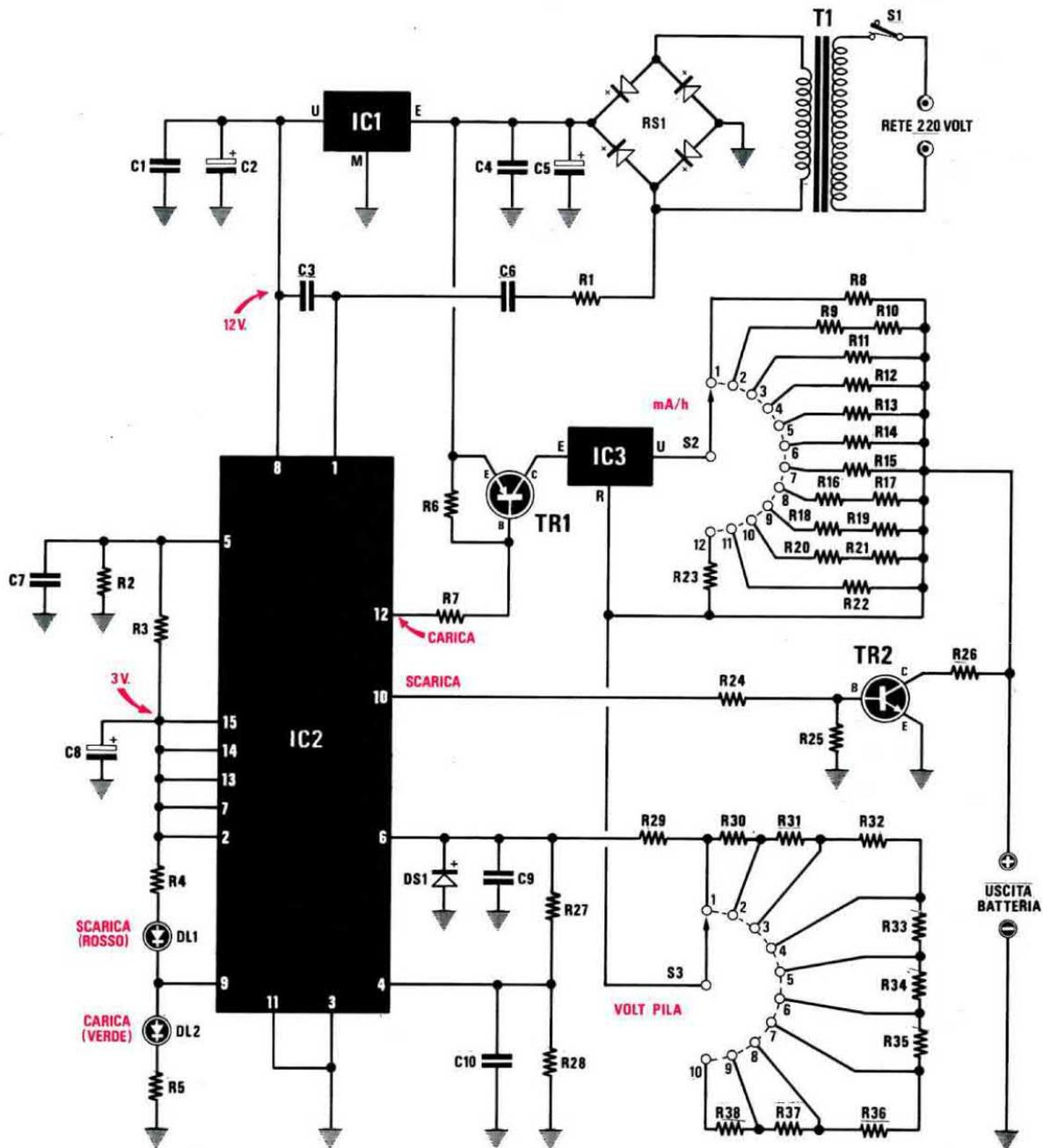
Fig.2 Schema elettrico del carica pile e connessioni degli stabilizzatori di tensione e dei due transistor TIP31 e BDX54.
