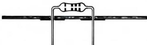
**Fig.3** Prima di inserire una resistenza in un circuito stampato, dovete ripiegarne i due terminali laterali con un paio di pinze, cercando di tenere il corpo della resistenza al centro delle due piegature.
