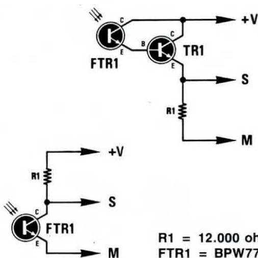
Fig.14 Se volete usare un solo fototransistor BPW.77, potrete utilizzare lo schema in basso a sinistra. Se volete aumentare la sensibilità potrete accoppiarlo in Darlington con un transistor NPN tipo BC.237 o altro equivalente.
