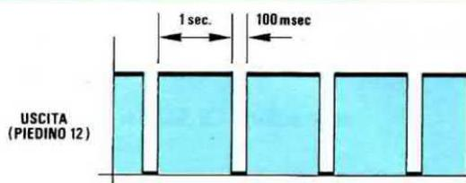
**Fig.3** In fase di ricarica, dal piedino 12 dell'integrato uscirà un impulso positivo della durata di 1 secondo con una pausa di 100 millisecondi. Pilotando con questi impulsi la base del Transistor TR1, la pila verrà ricaricata per 100 millisecondi seguiti da una pausa di 1 secondo.
