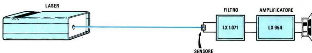
Fig.11 Vi converrà effettuare le prime prove di trasmissione a distanza ravvicinata, cioè a meno di 100 metri, cercando di centrare il fascio del Laser sulla superficie del sensore. Se modulando il fascio Laser notate che questo tende a spegnersi, significa che il segnale di BF ha un'ampiezza elevata. Se userete la radio (vedi fig.4), dovrete abbassare il "volume".
