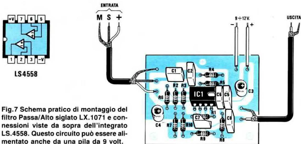
Fig.7 Schema pratico di montaggio del filtro Passa/Alto siglato LX.1071 e connessioni viste da sopra dell'integrato LS.4558. Questo circuito può essere alimentato anche da una pila da 9 volt.
