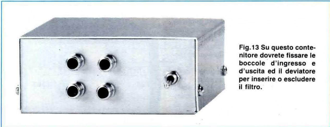
**Fig.13** Su questo contenitore dovrete fissare le boccole d'ingresso e d'uscita ed il deviatore per inserire o escludere il filtro.
