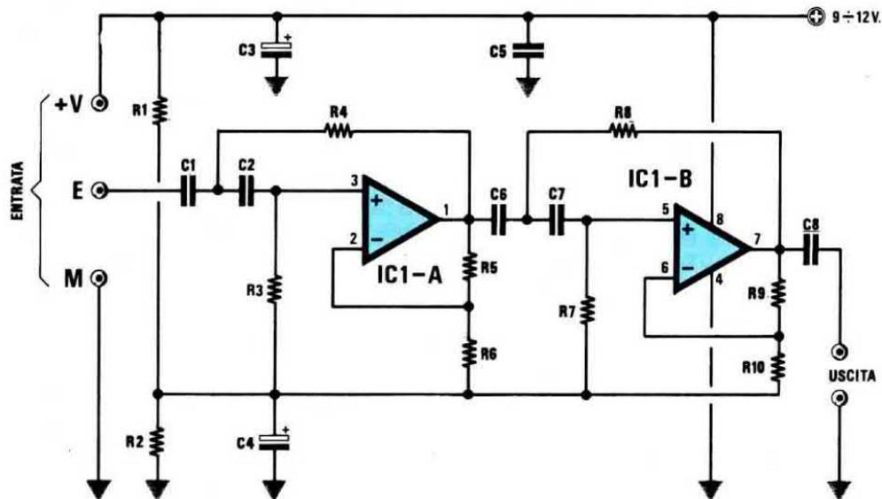
Fig.6 Poichè i fotosensori capteranno da qualsiasi lampada accesa il ronzio a 50 Hertz, per eliminarlo dovrete utilizzare questo filtro Passa/Alto con frequenza di taglio a 120-130 Hz. Ai terminali d'ingresso +V S M collegherete i corrispondenti terminali degli schemi riportati nelle figg.13-14-15-16.
