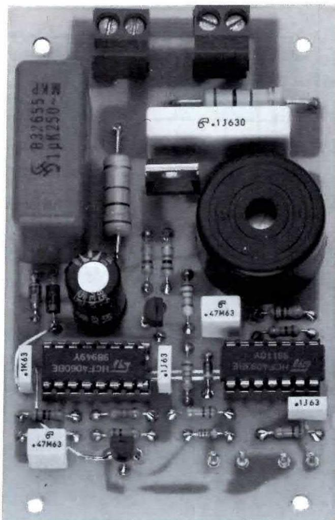
**Fig.6** Foto notevolmente ingrandita del progetto montato. Lo stampato che vi forniremo è provvisto di un disegno serigrafico completo che qui non appare, essendo questo uno degli esemplari da noi utilizzati per il collaudo.
