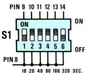
Fig.7 In questo esempio con le levette dei tempi 20-40-80-160 secondi spostate verso On, otterrete un tempo totale di 300 secondi che equivalgono a 5 minuti. Spostando verso On tutte le levette, otterrete un tempo totale di 630 secondi che equivalgono a 10 minuti e 30 secondi.
