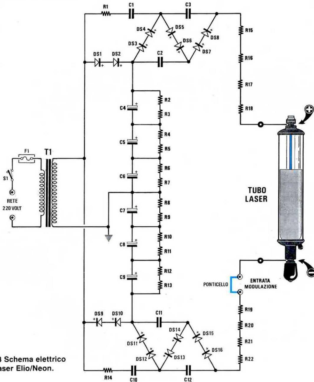
Fig.13 Schema elettrico del Laser Elio/Neon.
