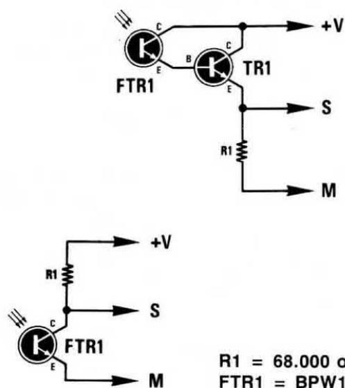
Fig.15 Se volete usare un solo fototransistor BPW.14 o S.252, potrete usare lo schema in basso a sinistra. Se volete fare delle prove su lunghe distanze, vi converrà accoppiarlo in Darlington con un transistor NPN tipo BC.237.
