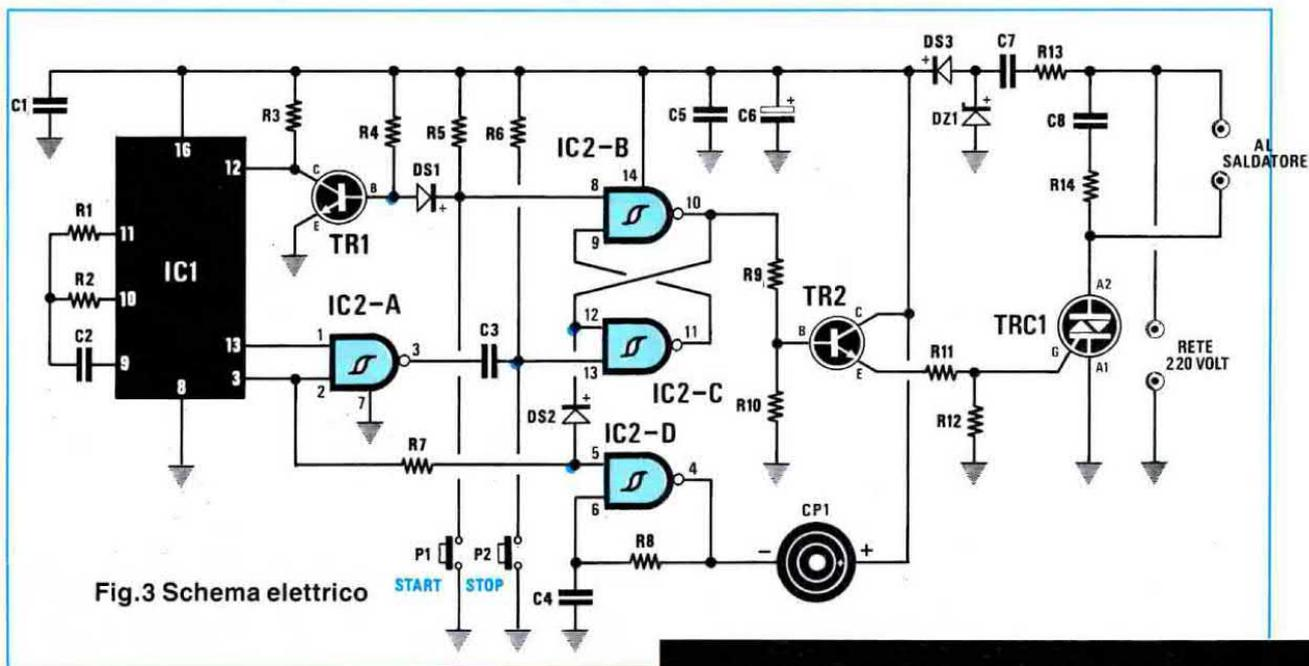
Fig.3 Schema elettrico
