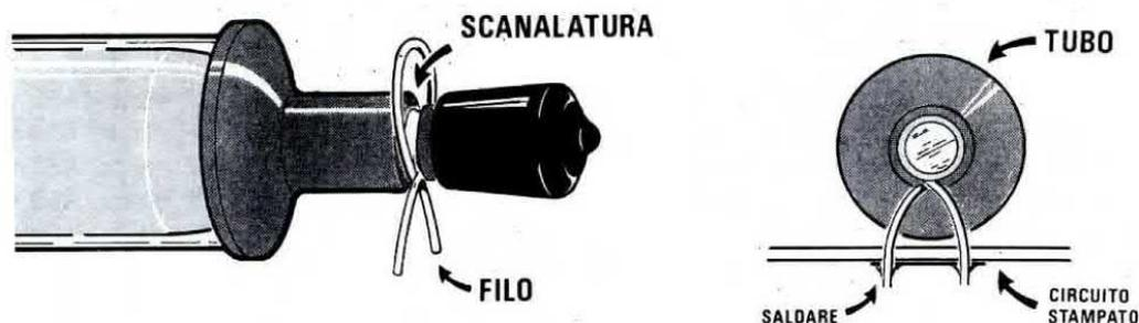
**Fig.14** Il tubo Laser andrà fissato direttamente sul circuito stampato (vedi fig.15). Poichè sui due perni metallici posti alle estremità del tubo sono presenti due scanalature, al loro interno si dovrà avvolgere una spira di filo di rame nudo, saldandone poi le due estremità alle piste in rame dello stampato.
