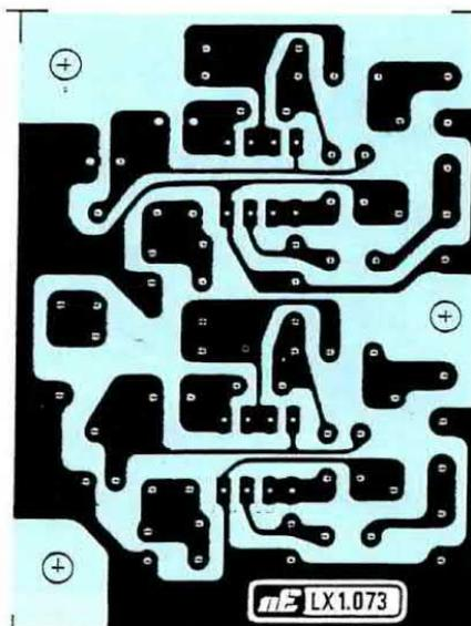
Fig.7 Disegno a grandezza naturale del circuito stampato LX.1073 visto del lato rame. Questo stampato serve per la realizzazione del filtro Passa/Alto.
