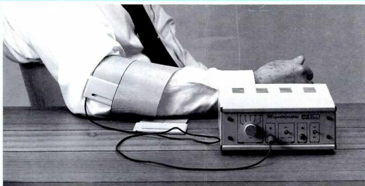
**Fig.5** Per accelerare la rigenerazione di tessuto osseo in corrispondenza di fratture agli arti, per eliminare i dolori acuti provocati da sciatiche o atrolisi del ginocchio, potrete avvolgere la fascia attorno alla zona interessata, anche sopra ai vestiti o alle ingessature.
