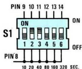
Fig.6 Se, come in questo esempio, sposterete le due levette dei tempi 20-40 secondi (vedi leve 2-3) verso l'alto, otterrete un temporizzatore che si spegnerà dopo  $20 + 40 = 60$  secondi. Agendo su queste 6 levette, potrete ottenere qualsiasi altro tempo con salti di 10 secondi.
