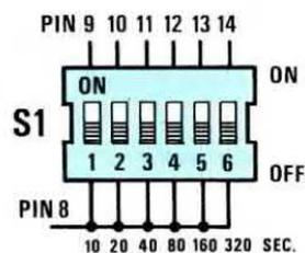
Fig.5 Per ottenere i tempi desiderati dovreste necessariamente spostare una delle 6 levette del dip-switch S1 verso l'alto, cioè su On. Se terrete tutte e 6 le levette rivolte verso Off, il temporizzatore "non funzionerà" perchè avrete scelto un tempo uguale a "zero".
