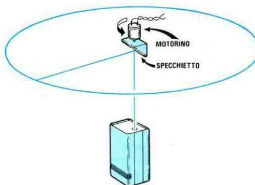
Fig.8 Ponendo il tubo Laser in posizione verticale e direzionando il fascio su un "prisma" che ruota velocemente, potrete ottenere una riga luminosa sulle quattro pareti di una stanza.
