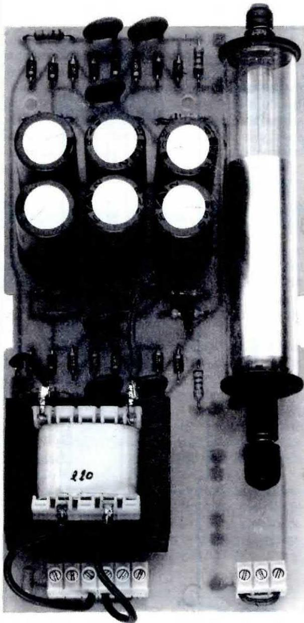
Fig.16 Foto del circuito Laser già montato. Poichè sulle due estremità del tubo Laser sono innestati due "tappi" in gomma per evitare che il vetro si sporchi, è ovvio che andrà tolto solo quello collocato anteriormente. Ricordatevi di cortocircuitare la morsettiera a 2 poli posta in basso a sinistra. Il trasformatore di alimentazione andrà fissato sullo stampato con quattro viti in ferro.
