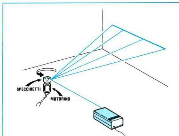
Fig.7 Fissando sul perno di un motorino un cubo in legno con sopra collocati degli specchietti, potrete ottenere sul muro una riga luminosa perfettamente orizzontale.
