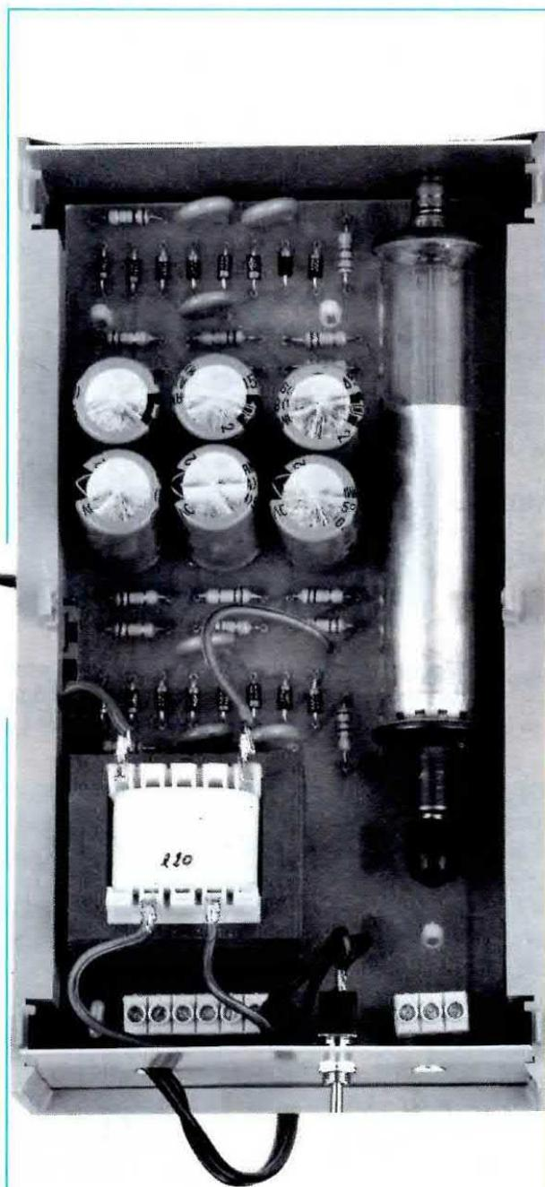
Fig.18 Il circuito stampato andrà fissato all'interno del mobile usando i quattro distanziatori plastici con base autoadesiva presenti nel kit. Prima di fissarli, ricordatevi di togliere dalla base di questi distanziatori la carta protettiva. L'interruttore di rete S1 andrà fissato sul pannello posteriore.
