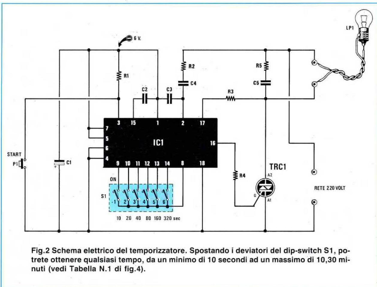
**Fig.2 Schema elettrico del temporizzatore. Spostando i deviatori del dip-switch S1, potrete ottenere qualsiasi tempo, da un minimo di 10 secondi ad un massimo di 10,30 minuti (vedi Tabella N.1 di fig.4).**
