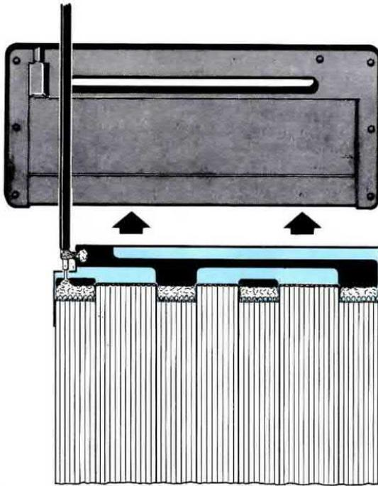
**Fig.9** Saldati i fili della piattina sui due circuiti stampati, potrete inserirli entro al vano di ogni semiguscio in plastica, ponendo poi sopra a questo l'altro semiguscio che vi si innesterà a pressione.
