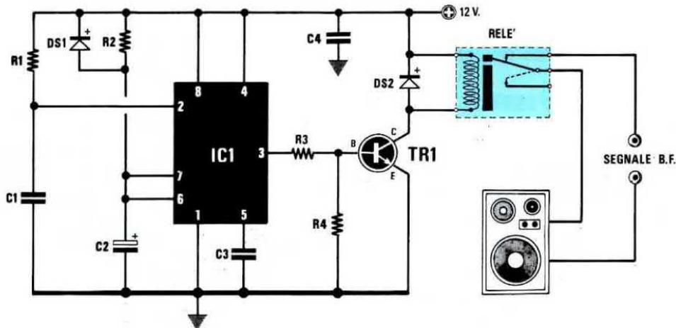
Fig.3 Schema elettrico di un ANTI-BUMP che potrà essere utilizzato per collegare ad un amplificatore le Casse Acustiche quando tutti i condensatori elettrolitici si saranno totalmente caricati. Il circuito andrà alimentato con una tensione di 12 volt.
