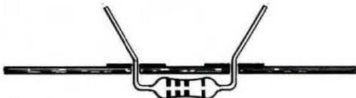
**Fig.4** Per evitare che la resistenza o il condensatore possano fuoriuscire dal circuito stampato quando lo capovolgerete per effettuare la saldatura, dovete divaricare "leggermente" i suoi due terminali.
