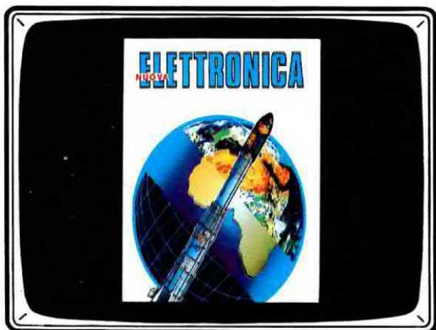
Fig.6 Visualizzando l'immagine RIVISTA in un formato più ridotto, ad esempio il 640 x 350, questa si allungherà, pertanto la parte inferiore di tale immagine risulterà tagliata.
