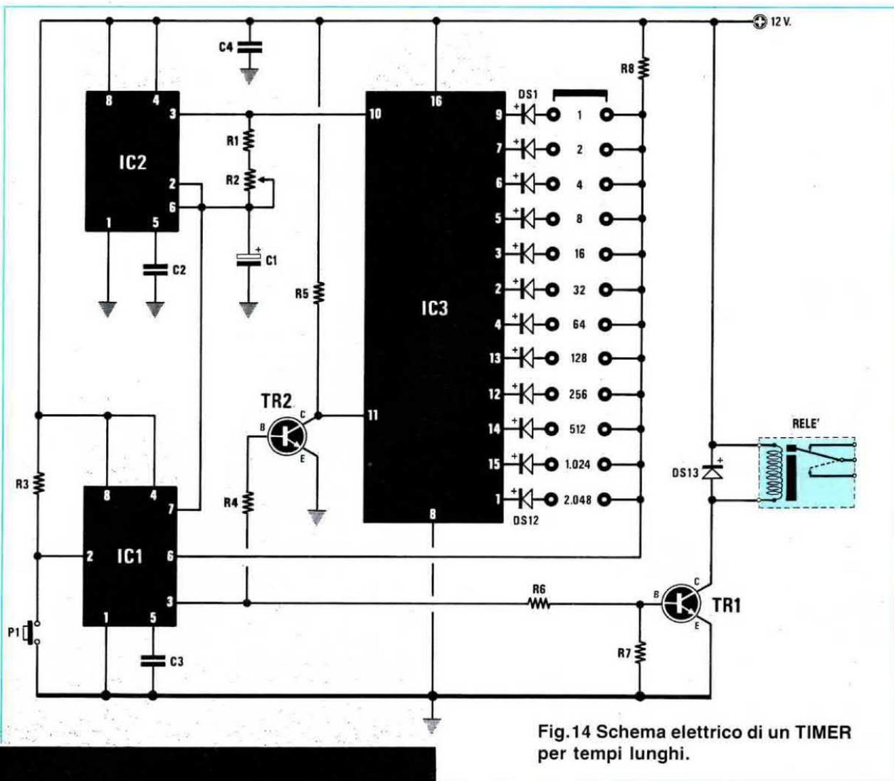
Fig. 14 Schema elettrico di un TIMER per tempi lunghi.
