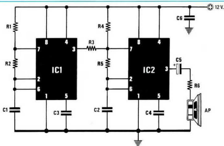
Fig.16 Schema elettrico di un generatore BITONALE.
