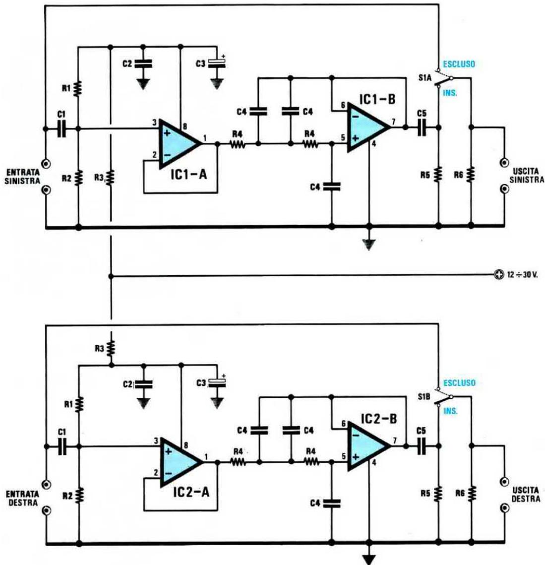
Fig.9 Schema elettrico del filtro Passa/Basso STEREO che noi forniamo con quattro condensatori C4 da 3.300 pF e quattro resistenze R4 da 3.300 ohm, in modo da ottenere una frequenza di taglio sui 10.000 Hz circa. Coloro che volessero modificare la frequenza di taglio, potranno ricavare dalla Tabella n.3 i valori da utilizzare per C4-R4.
