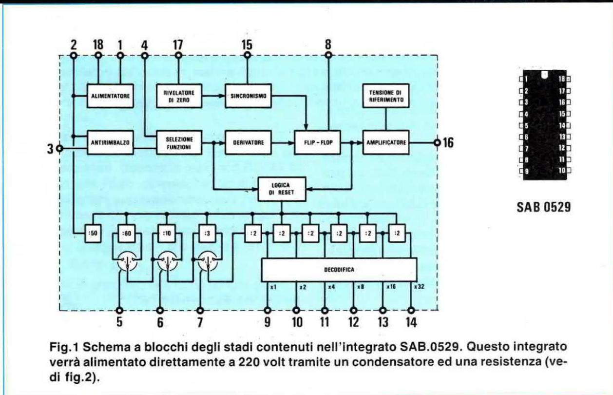
Fig.1 Schema a blocchi degli stadi contenuti nell'integrato SAB.0529. Questo integrato verrà alimentato direttamente a 220 volt tramite un condensatore ed una resistenza (vedi fig.2).
