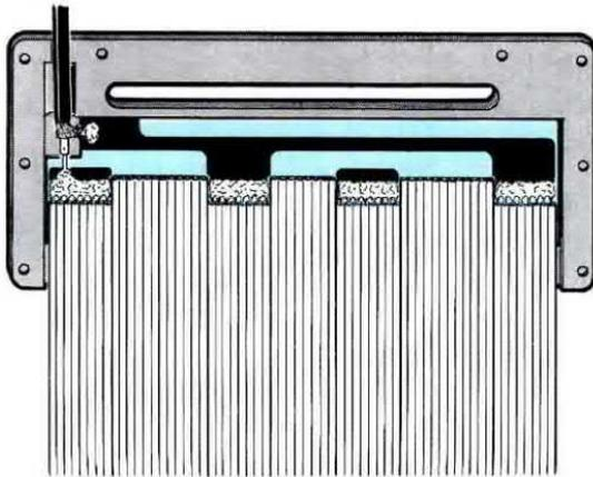
**Fig.10** Prima di chiudere i due gusci, controllate attentamente che la calza di schermo del cavetto coassiale risulti ben saldata sulla sua pista in rame. Se con il passare del tempo, i due gusci dovessero aprirsi perchè i perni d'innesto si saranno consumati, potrete fissarli con una goccia di collante.
