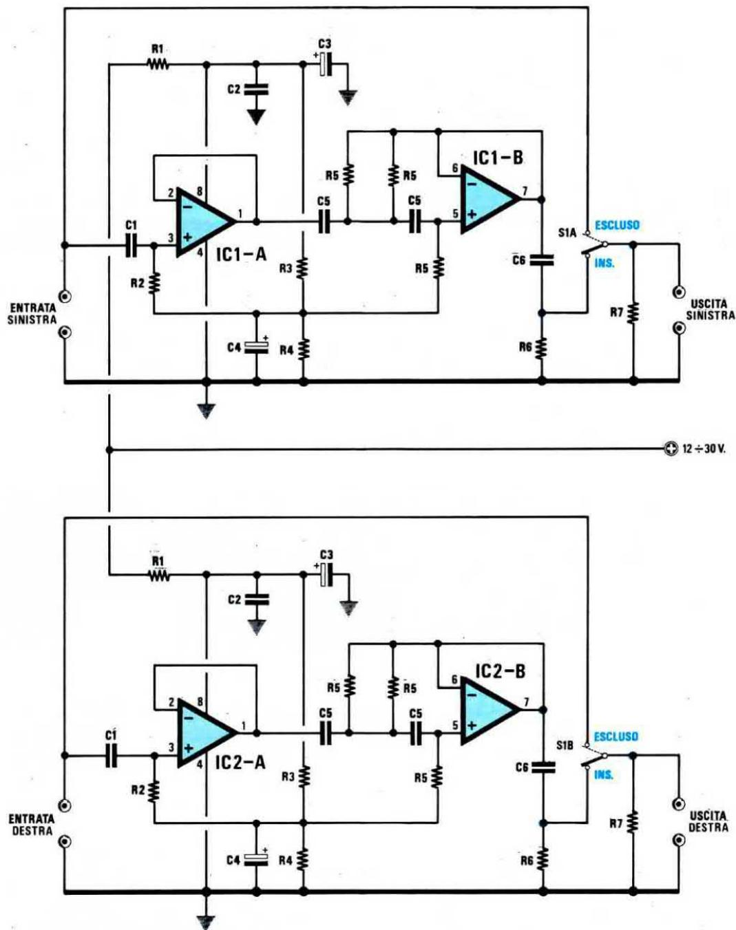
Fig.3 Schema elettrico del filtro Passa/Alto STEREO che noi forniamo con quattro condensatori C5 da 100.000 pF e quattro resistenze R5 da 18.000 ohm, in modo da ottenere una frequenza di taglio sui 125 Hz circa. Coloro che volessero modificare la frequenza di taglio, potranno ricavare dalla Tabella n.2 dei valori da utilizzare per C5-R5.
