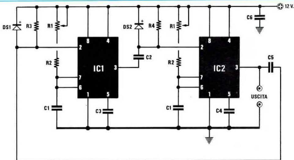
Fig. 15 Schema elettrico di uno SPACE-MARKER.
