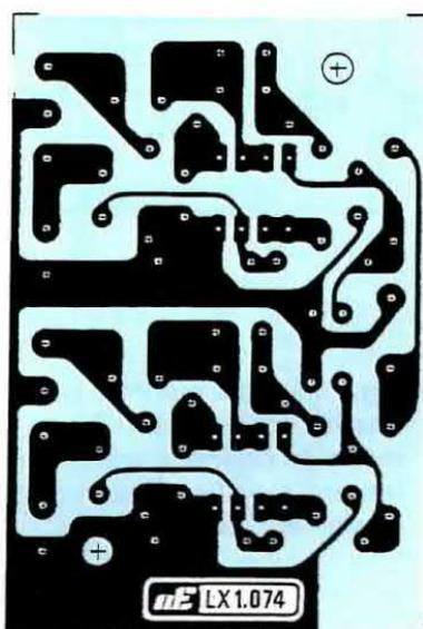
Fig.8 Disegno a grandezza naturale del circuito stampato LX.1074 visto dal lato rame. Questo stampato serve per la realizzazione del filtro Passa/Basso.
