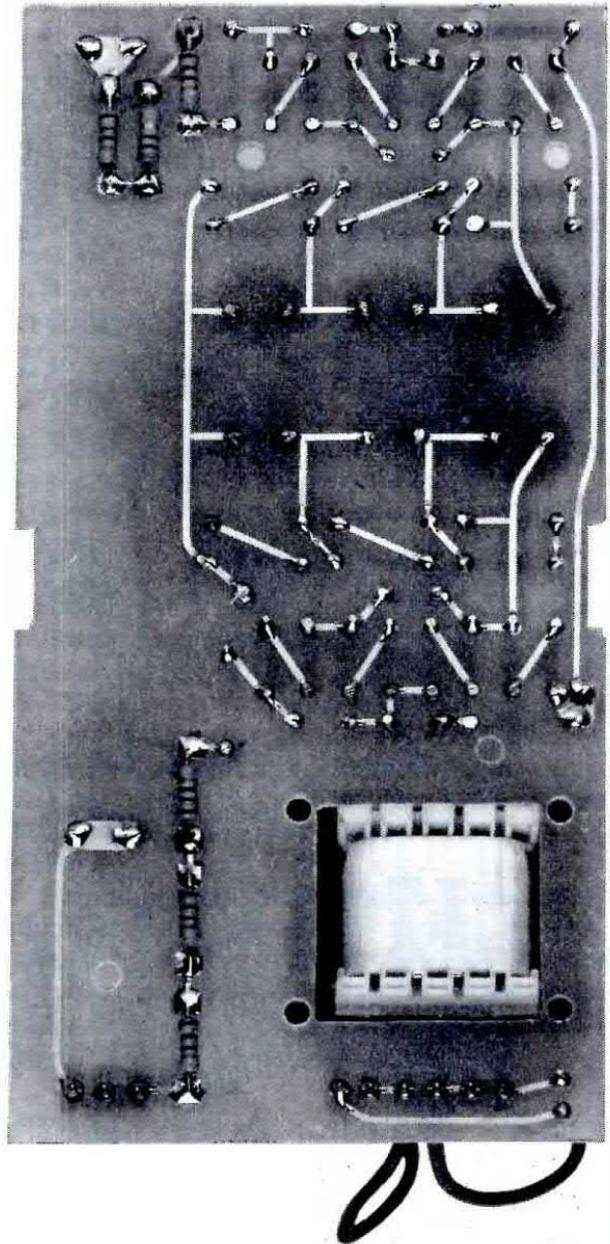
Fig.17 Sulla parte posteriore dello stampato andranno saldate, direttamente sulle piste in rame, le resistenze siglate R16-R17-R18-R20-R21-R22 (vedi nello schema pratico di fig.15 le resistenze tratteggiate). Usate per le saldature stagno di ottima qualità, provvisto di un disossidante che non lasci molto residuo.
