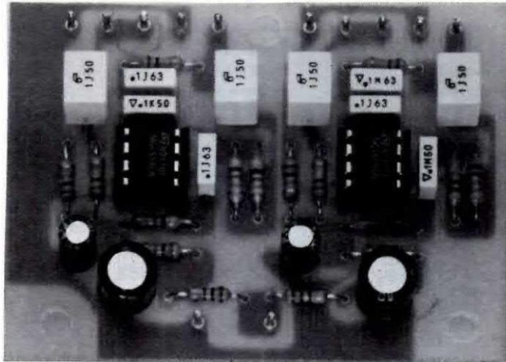
Fig.5 In basso, lo schema pratico di montaggio di questo filtro. Ricordatevi di collegare le calze dei due cavetti schermati che partono dalle bocche d'uscita alle calze dei due cavetti che vanno al circuito stampato.
