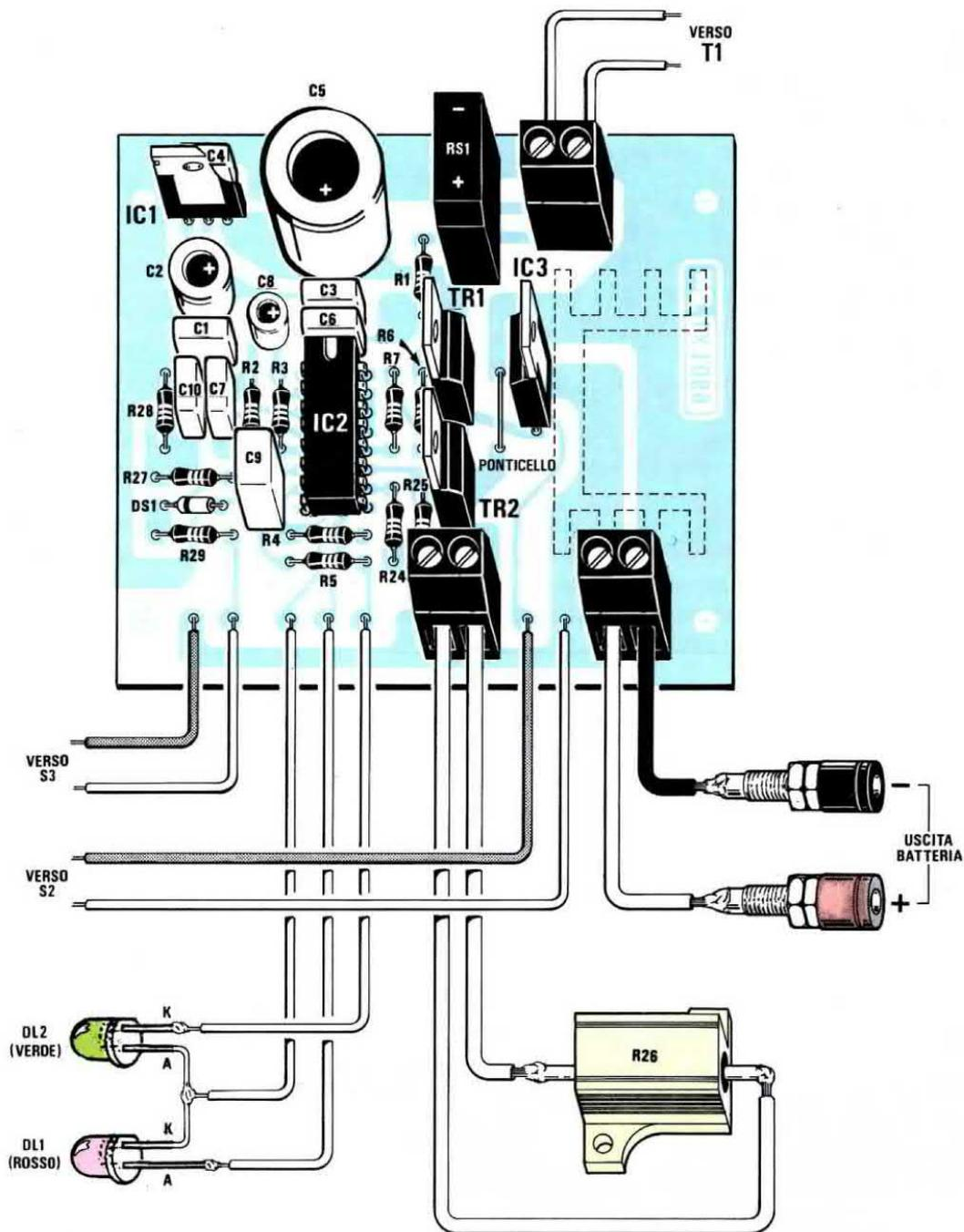
Fig.8 Schema pratico di montaggio del caricapile al Nichel-Cadmio. Come visibile nel disegno, tra il transistor TR1 e l'integrato IC3 dovreste inserire un ponticello utilizzando uno spezzone di filo di rame nudo. La resistenza corazzata R26 andrà fissata sulla base metallica del mobile per poterla raffreddare più velocemente. Attenzione a non invertire la polarità delle due boccole d'uscita Positiva e Negativa.
