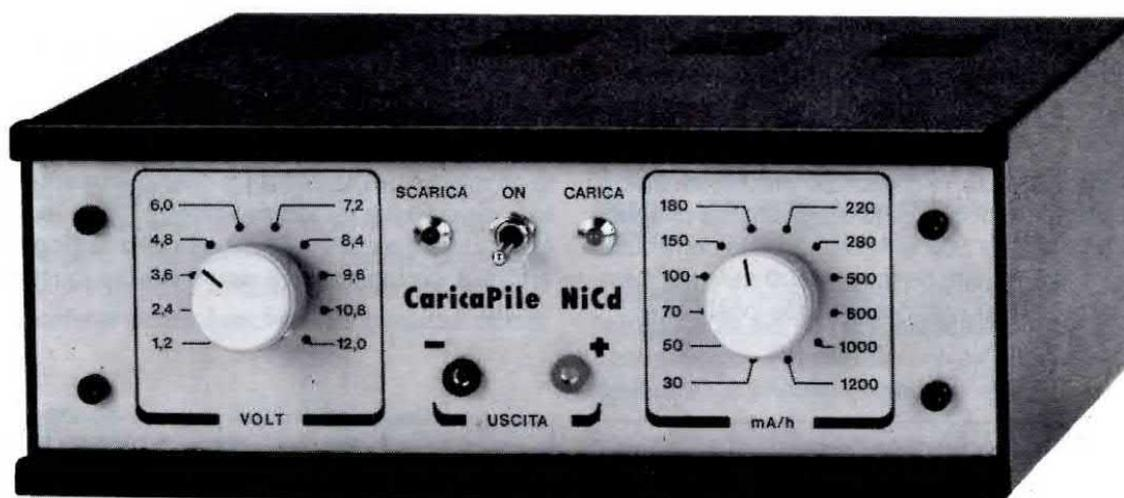
**Fig.4** Sul pannello frontale del mobile sono presenti due manopole, quella dei volt e quella dei milliamper/ora, più i due diodi led di controllo. La manopola dei volt andrà ruotata sul valore della tensione della pila, mentre la manopola dei mA/h sulla capacità della pila, quasi sempre indicata sull'involucro. Prima di inserire la pila, dovrete ruotare questi due commutatori sull'esatto valore di tensione e di corrente. Non ruotate mai il commutatore della tensione con la pila inserita.
