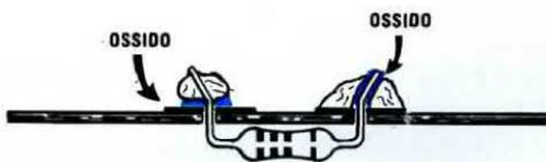
**Fig.8** Se depositerete dello stagno già fuso sul saldatore, sul terminale di una resistenza, esso potrà ugualmente "attaccarsi", ma sulla superficie potrà rimanere un sottile strato di ossido che impedirà un perfetto "contatto" elettrico.
