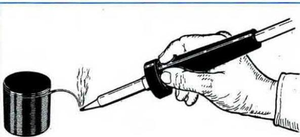
**Fig.7** Sciogliendo lo stagno sulla punta del saldatore per poi depositarlo sulla pista dello stampato, il disossidante "pulirà" soltanto la superficie della punta, ma non il terminale ossidato della resistenza o della pista in rame del circuito stampato.
