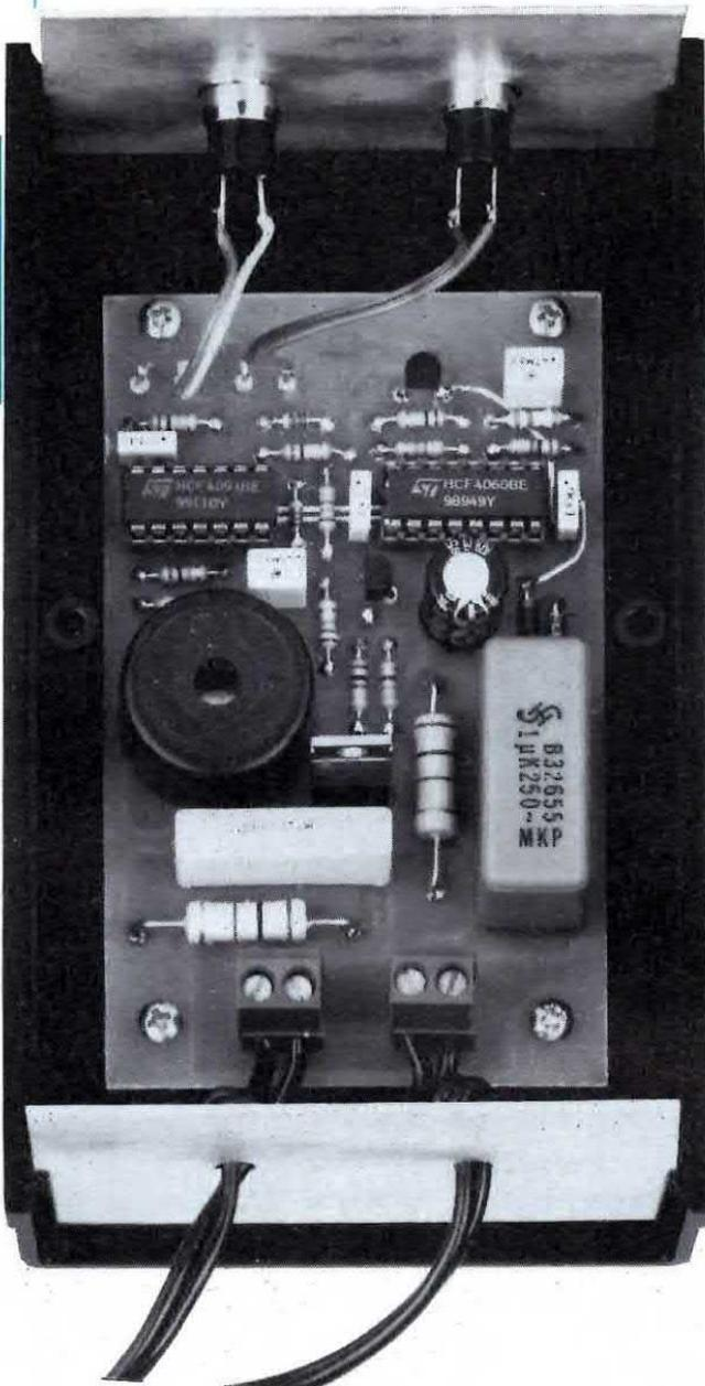
Fig.2 Il kit LX.1075 già inserito all'interno del relativo mobile plastico. I due pulsanti di Start e Stop andranno fissati sul pannello frontale del mobile.
