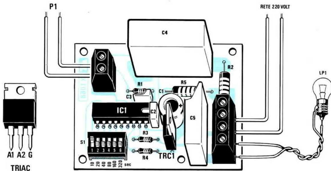
Fig.3 Schema pratico di montaggio e connessioni del Triac. Alla morsettiere collocata sul lato sinistro, collegherete i fili provenienti da tutti i pulsanti installati sulla scala e sull'ingresso. **NON TOCCATE** a temporizzatore inserito alcun componente, perchè su ciascuno di essi sarà presente la tensione di rete.
