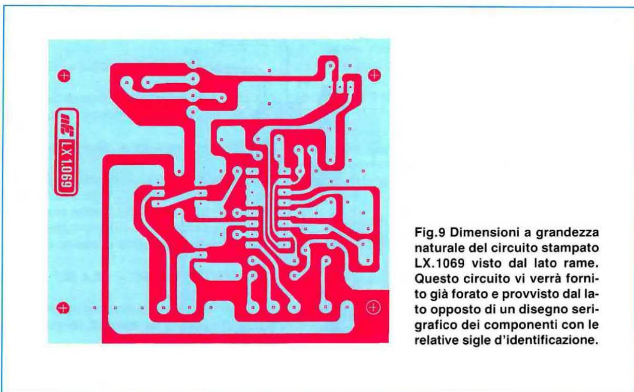
**Fig.9** Dimensioni a grandezza naturale del circuito stampato LX.1069 visto dal lato rame. Questo circuito vi verrà fornito già forato e provvisto dal lato opposto di un disegno serigrafico dei componenti con le relative sigle d'identificazione.
